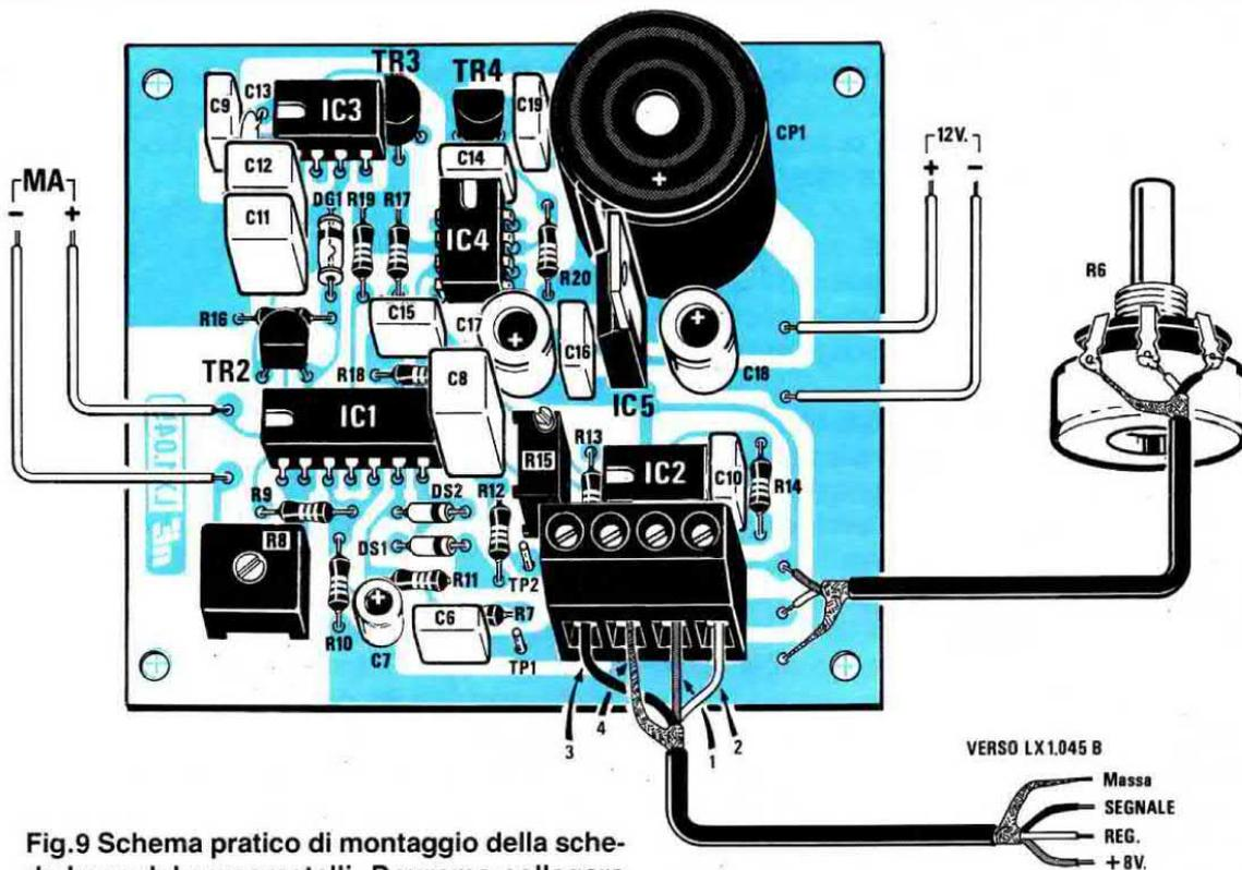
Fig.9 Schema pratico di montaggio della scheda base del cercametalli. Dovremo collegare i due fili indicati MA al microamperometro, e i due fili indicati 12 V alla presa visibile in fig.12.
