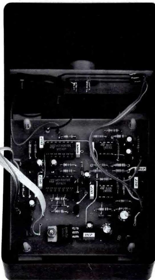
**Fig.14** La scheda LX.1083 andrà fissata all'interno del mobile, mentre la scheda del display siglata LX.1083/B andrà fissata sul pannello frontale tramite quattro distanziatori plastici autoadesivi.
