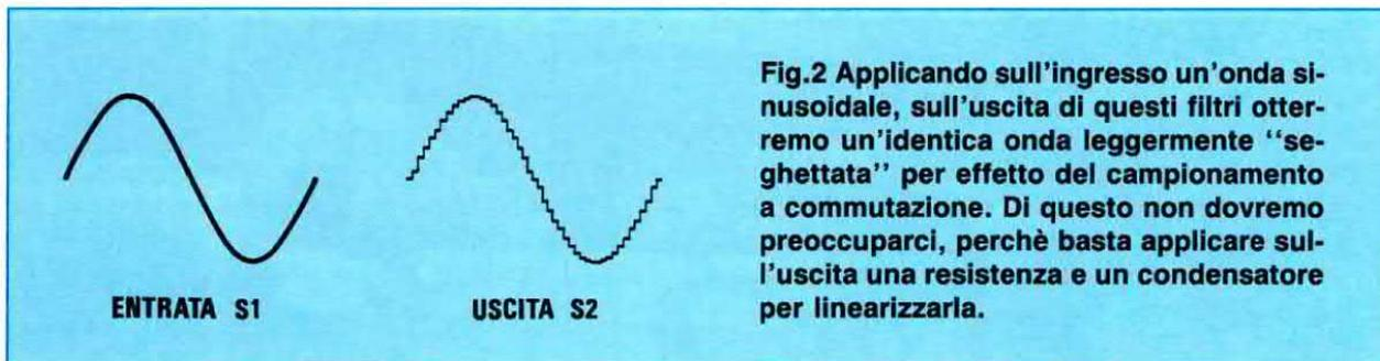
le filtro un'onda sinusoidale di **250 Hz** che abbia un'ampiezza massima di **1 volt**.
