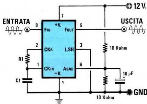
Fig.10 Se alimenterete l'integrato con una tensione "singola" dovrete collegare a massa il piedino 3 (LSH) e il condensatore C1, mentre il piedino 6 (A/Gnd) andrà collegato ad un partitore resistivo composto da due resistenze da 10.000 ohm più un elettrolitico.
