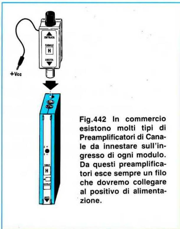
Fig.442 In commercio esistono molti tipi di Preamplificatori di Canale da innestare sull'ingresso di ogni modulo. Da questi preamplificatori esce sempre un filo che dovremo collegare al positivo di alimentazione.
