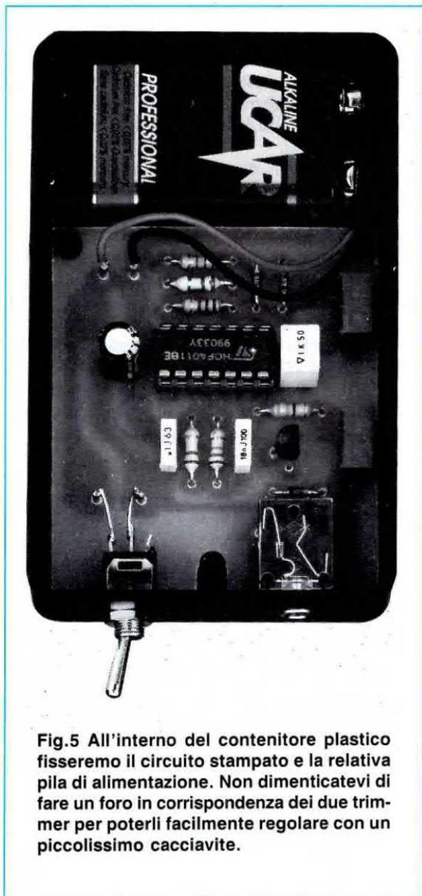
**Fig.5** All'interno del contenitore plastico fisseremo il circuito stampato e la relativa pila di alimentazione. Non dimenticatevi di fare un foro in corrispondenza dei due trimmer per poterli facilmente regolare con un piccolissimo cacciavite.
