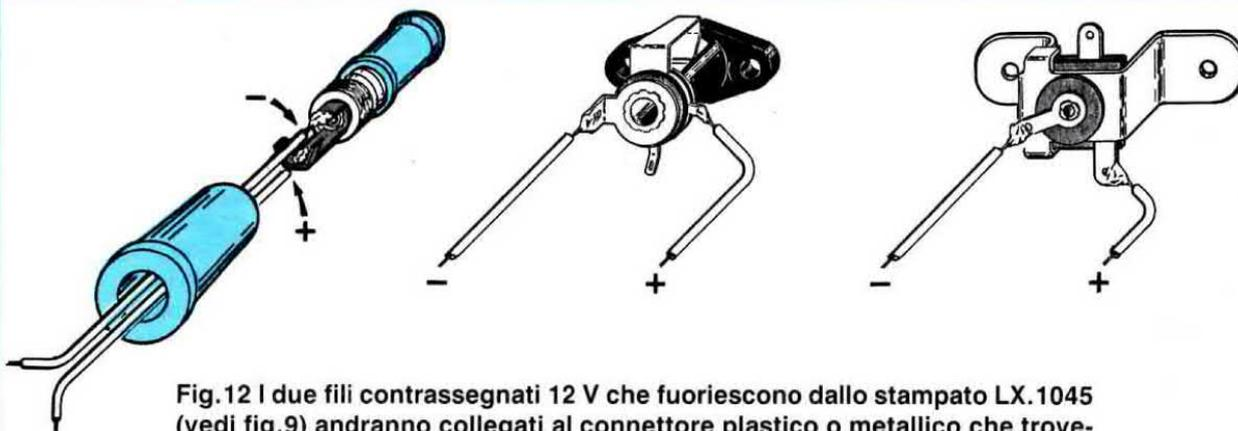
Fig. 12 I due fili contrassegnati 12 V che fuoriescono dallo stampato LX.1045 (vedi fig.9) andranno collegati al connettore plastico o metallico che troverete nel kit. Sul lato sinistro è visibile lo spinotto maschio che inseriremo in questo connettore per fornire tensione al cercametalli. Attenzione a rispettare la polarità positiva e negativa di alimentazione.
