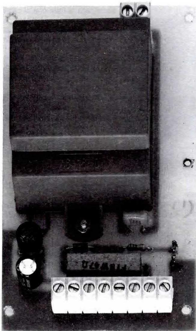
**Fig.10** Foto del caricabatteria siglato LX.1097/C. Si noti in basso a destra vicino al trasformatore di alimentazione il piccolo fusibile "autoripristinante" che provvederà automaticamente ad interrompere la tensione di rete in presenza di un cortocircuito e di reinserirla quando questo cortocircuito non risulterà più presente.
