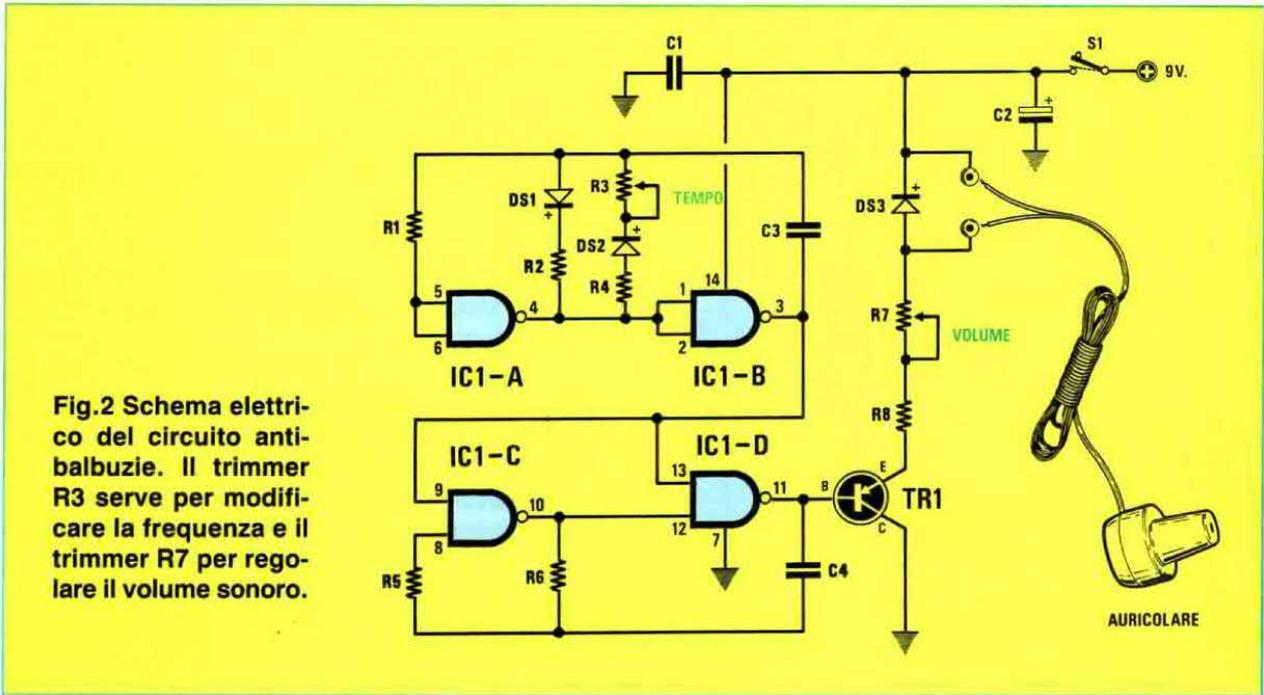
Fig.2 Schema elettrico del circuito anti-balubuzie. Il trimmer R3 serve per modificare la frequenza e il trimmer R7 per regolare il volume sonoro.
