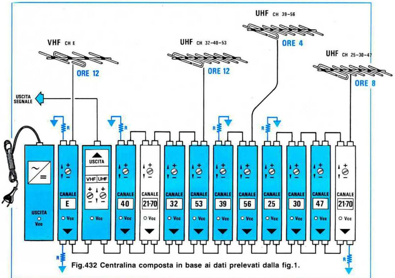
Per quanto riguarda l'antenna direzionata verso le **ore 8**, verificato che i segnali da questa direzione giungono molto deboli (non superano i **70 dBmicrovolt**) dobbiamo necessariamente **preamplificarli**.
