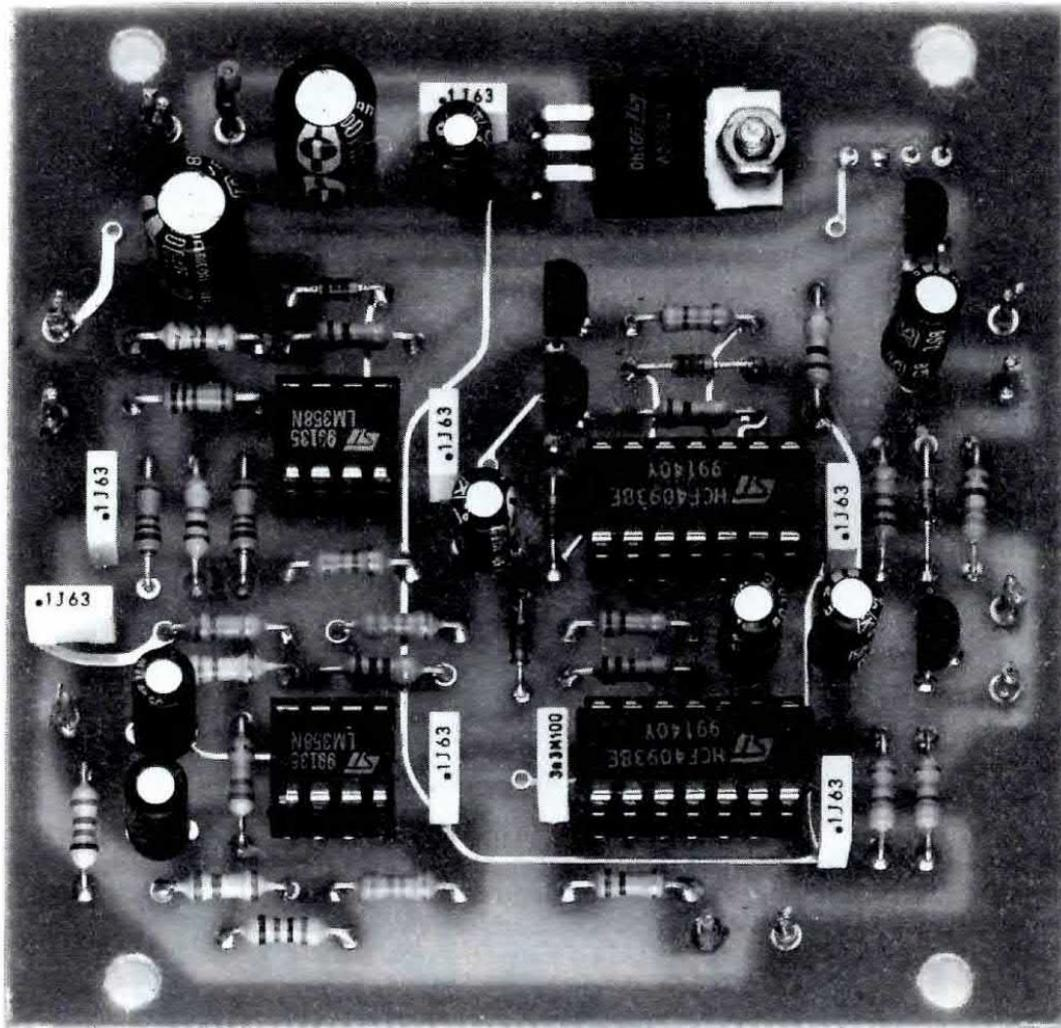
**Fig.4** Foto notevolmente ingrandita dello stampato LX.1083, con tutti i componenti già montati. Anche se in questa foto non è visibile, lo stampato è completo di disegno serigrafico che aiuterà il lettore a trovare la giusta posizione di ogni componente.
