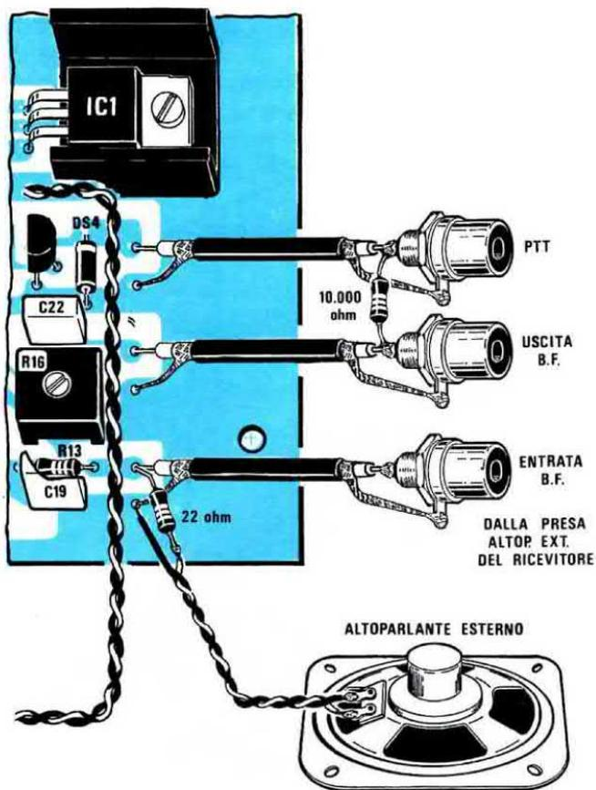
Fig.6 Se il vostro ricevitore non dispone di un ingresso PTT, dovrete inserire tra questa uscita (che non verrà utilizzata) e l'“uscita BF” che si collegherà alla presa “microfono”, una resistenza da 10.000 ohm. Per ascoltare il segnale che riceveremo, potremo usare un piccolo altoparlante che collegheremo sulla presa “entrata BF” tramite una resistenza da 22-33 ohm.
