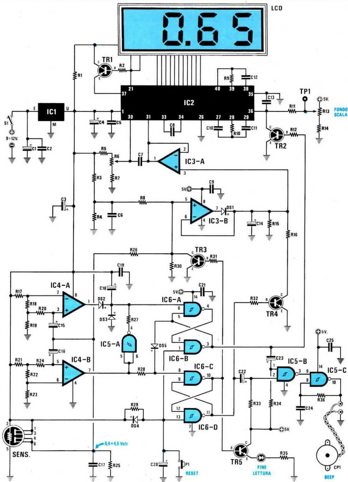
Fig.3 Schema elettrico dell'Etilometro elettronico. Il circuito viene alimentato esternamente con una tensione compresa tra 9-12 volt. Normalmente si preleva questa tensione dalla batteria dell'auto tramite la presa accendisigaro. Non è consigliabile alimentarlo con delle normali pile da 9 volt perchè queste si scaricherebbero in breve tempo.
