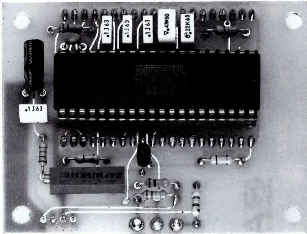
**Fig.5** Foto notevolmente ingrandita dello stampato LX.1083/B vista dal lato dell'integrato ICL.7106. Come visibile in fig.11, dal lato opposto di questo stampato, verranno montati i due connettori femmina necessari per il display a cristalli liquidi.
