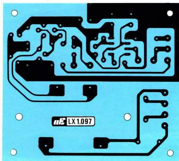
**Fig.15** Disegno a grandezza naturale del circuito stampato siglato LX.1097 visto dal lato rame. Lo stampato che vi forniremo risulta forato e completo dal lato opposto di un disegno serigrafico di ogni componente con la relativa sigla.
