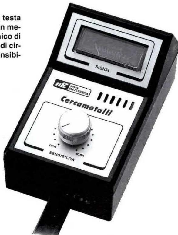
**Fig. 15** Il contenitore plastico di comando, fissato sull'estremità superiore del manico di alluminio, permetterà all'operatore di poter facilmente ruotare la manopola della sensibilità e vedere la lancetta dello strumento.
