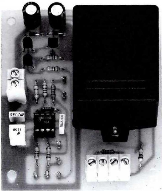
Fig.7 Terminato il montaggio del circuito base LX.1097 questo si presenterà come visibile in questa foto. Si noti sulla sinistra la morsettiera a 2 poli necessaria per l'ingresso della tensione di alimentazione, e in basso la morsettiera a 4 poli utilizzata per le due placche in gomma conduttrici e per il collegamento al potenziometro R16.
