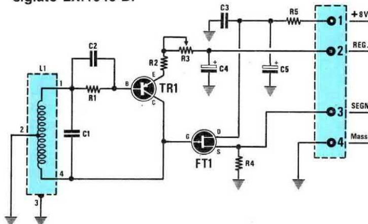
Fig.1 Schema elettrico del cercametalli. Questo circuito controlla, all'atto dell'accensione, se il terreno è leggermente ferroso, e la sua densità viene "memorizzata" sul condensatore C8.
