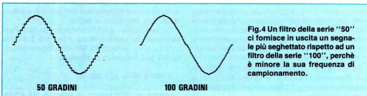
Fig.4 Un filtro della serie "50" ci fornisce in uscita un segnale più seghettato rispetto ad un filtro della serie "100", perchè è minore la sua frequenza di campionamento.
