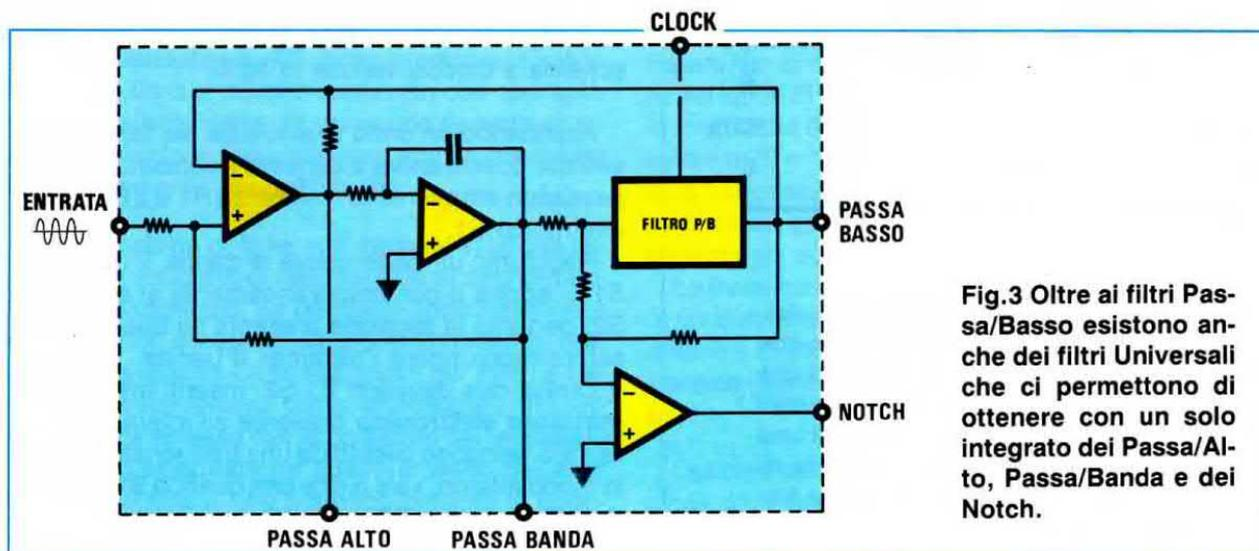
Fig.3 Oltre ai filtri Passa/Basso esistono anche dei filtri **Universali** che ci permettono di ottenere con un solo integrato dei Passa/Alto, Passa/Banda e dei Notch.
