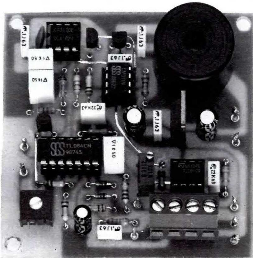
Fig.10 Foto ingrandita della scheda base con tutti i componenti già montati.
