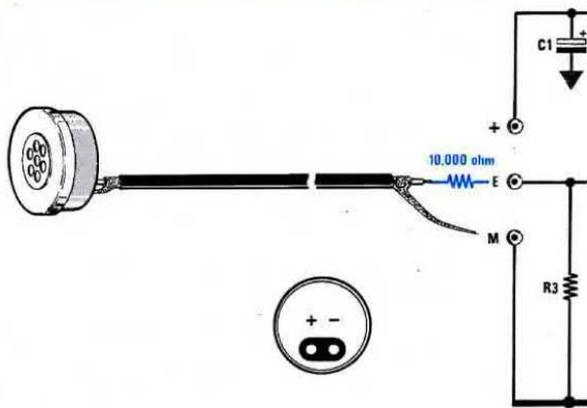
Fig.7 Nello schema pratico di fig.5 troverete per l'ingresso microfono tre terminali indicati + E M. Se impiegate dei microfoni "piezoelettrici" dovrete usare i due soli ingressi E M. Se il microfono dovesse risultare molto sensibile, converrà collegare in serie al terminale E una resistenza da 10.000 ohm.
