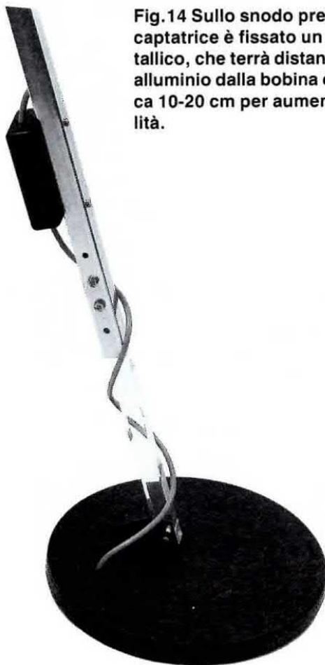
**Fig. 14** Sullo snodo presente nella testa captatrice è fissato un righello non metallico, che terrà distanziato il manico di alluminio dalla bobina oscillatrice di circa 10-20 cm per aumentarne la sensibilità.
