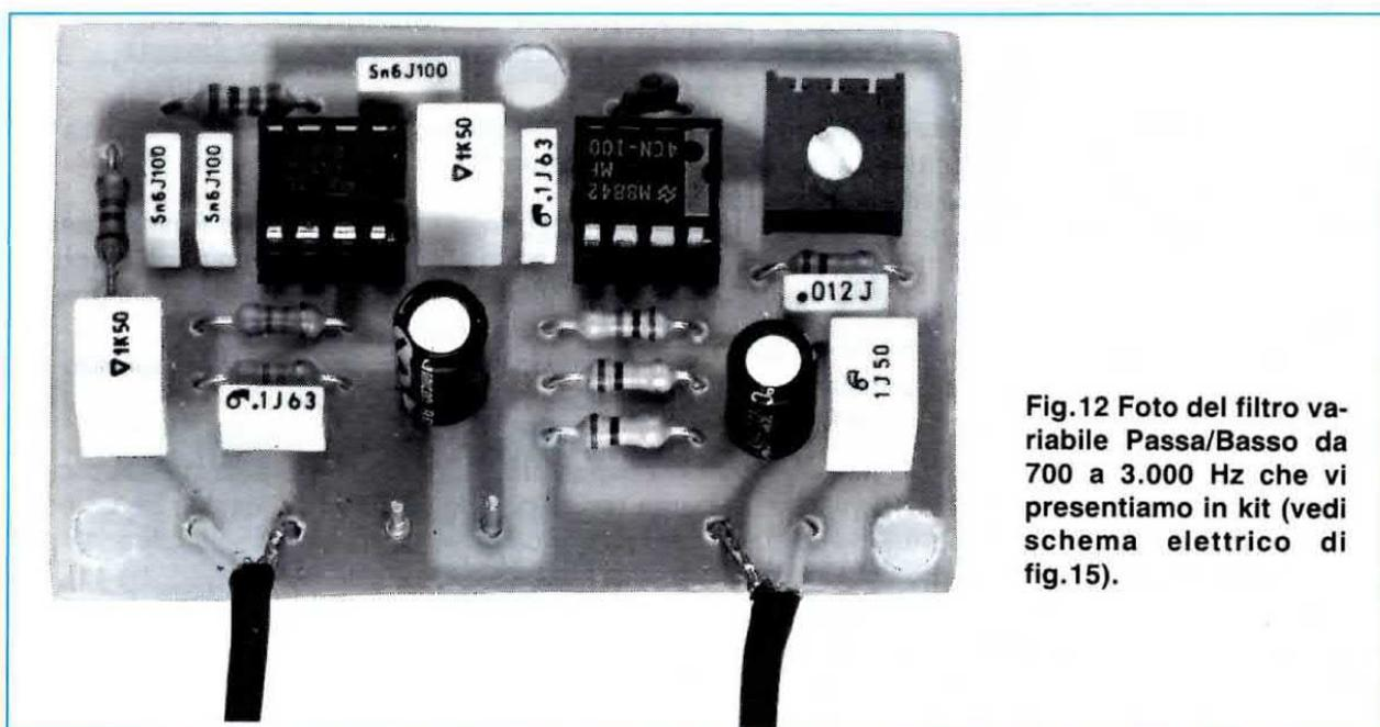
Fig.12 Foto del filtro variabile Passa/Basso da 700 a 3.000 Hz che vi presentiamo in kit (vedi schema elettrico di fig.15).
