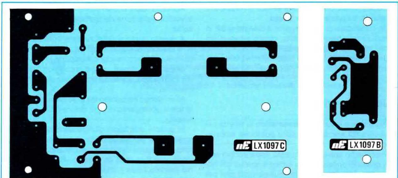
Fig.16 Disegno a grandezza naturale dello stampato siglato LX.1097/C da utilizzare per lo stadio caricabatteria e dello stampato LX.1097/B da utilizzare per il circuito di visualizzazione. Anche questi due circuiti stampati sono visti dal lato rame.
