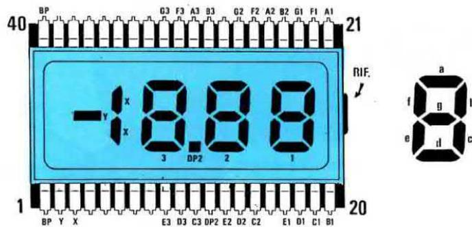
Fig.11 Dal lato opposto di questa scheda porremo il display LCD. Prima di inserire questo display nel suo zoccolo controllate attentamente da quale lato si trova la piccolissima goccia di vetro che serve da tacca di riferimento. Se questa tacca non verrà rivolta verso destra non permetterà al display di accendersi.
