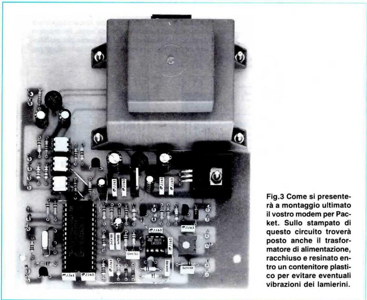
**Fig.3** Come si presenterà a montaggio ultimato il vostro modem per Packet. Sullo stampato di questo circuito troverà posto anche il trasformatore di alimentazione, racchiuso e resinato entro un contenitore plastico per evitare eventuali vibrazioni dei lamierini.
