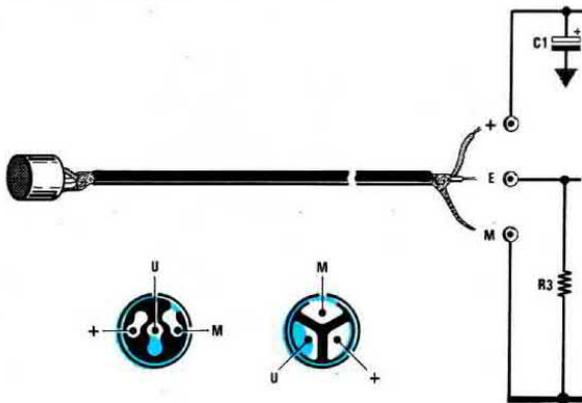
Fig.9 Se usate dei microfoni "preamplificati" provvisti di 3 piste dovrete collegare il terminale U (uscita segnale) al terminale E, la calza metallica al terminale M e il terminale di alimentazione al terminale +.
