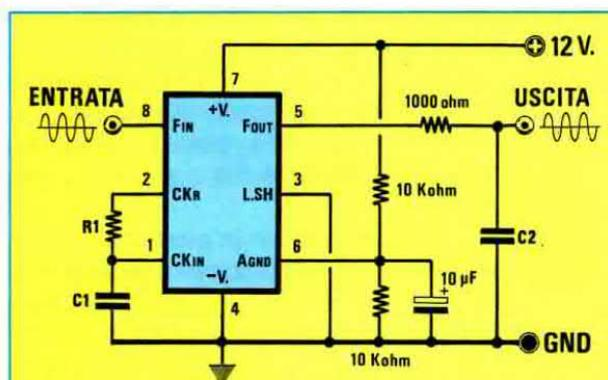
Fig.11 Nella fig.4 vi abbiamo precisato che l'onda sinusoidale che esce da un filtro digitale, è sempre leggermente "seghettata". Per togliere questa seghettatura è sufficiente applicare sull'uscita del filtro una resistenza da 1.000 ohm e un condensatore la cui capacità possiamo ricavare dalla
