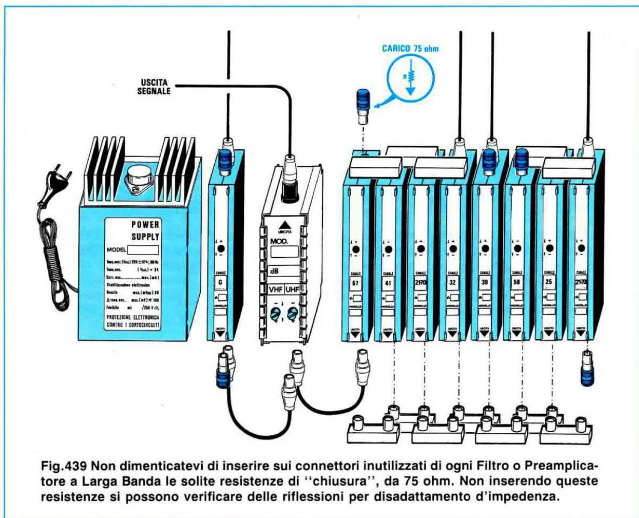
**Fig.439** Non dimenticatevi di inserire sui connettori inutilizzati di ogni Filtro o Preamplificatore a Larga Banda le solite resistenze di "chiusura", da 75 ohm. Non inserendo queste resistenze si possono verificare delle riflessioni per disadattamento d'impedenza.
