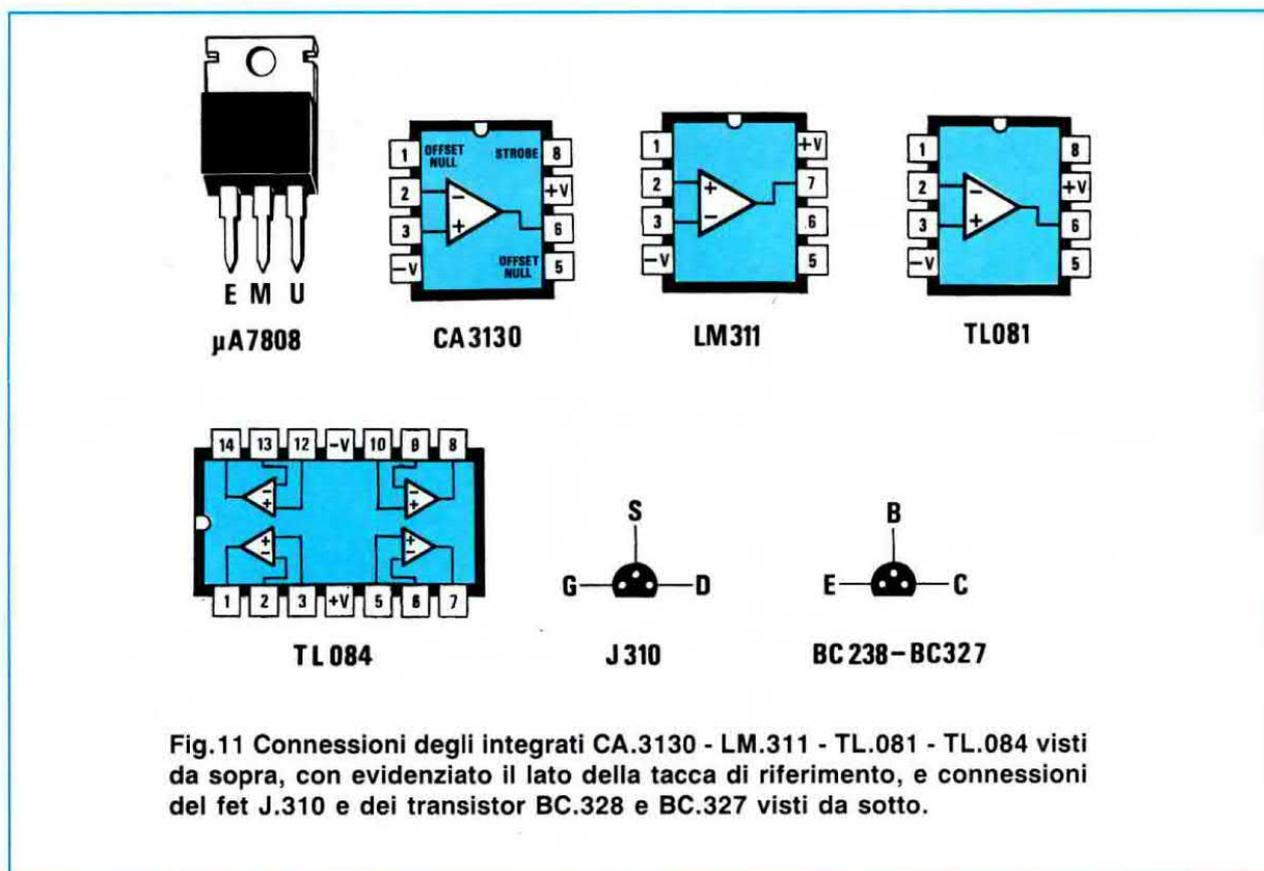
Fig.11 Connessioni degli integrati CA.3130 - LM.311 - TL.081 - TL.084 visti da sopra, con evidenziato il lato della tacca di riferimento, e connessioni dei fet J.310 e dei transistor BC.328 e BC.327 visti da sotto.
