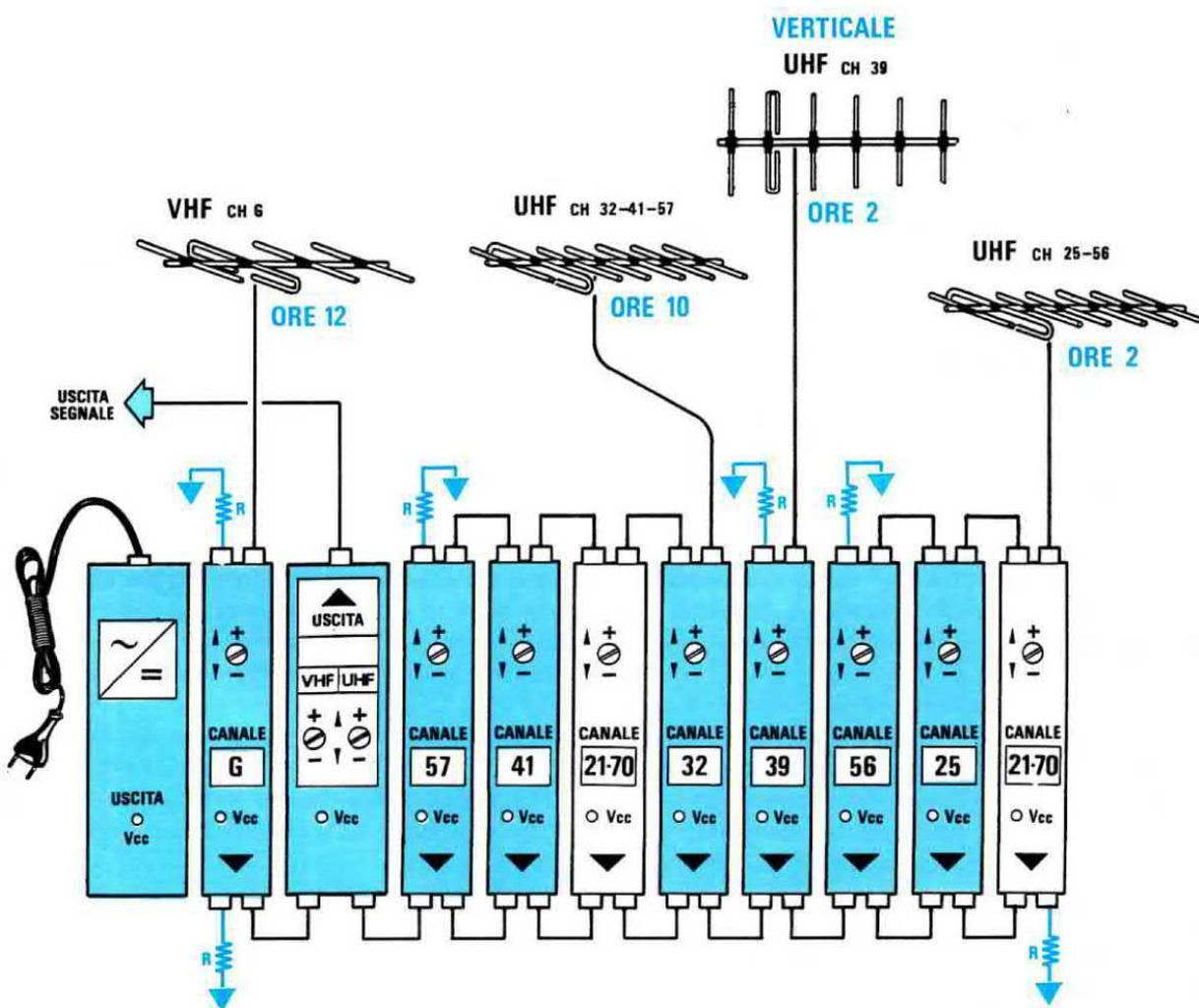
Fig.438 Anche se il "Canale 39" giunge dalla stessa direzione dei Canali 25-56, poichè questo segnale dispone di una polarizzazione "verticale", dovremo installare una seconda antenna UHF, posta a differenza dell'altra in senso verticale. Completata la Centralina dovremo equalizzare tutti i segnali come già spiegato nelle figg.433-434-435-436.
