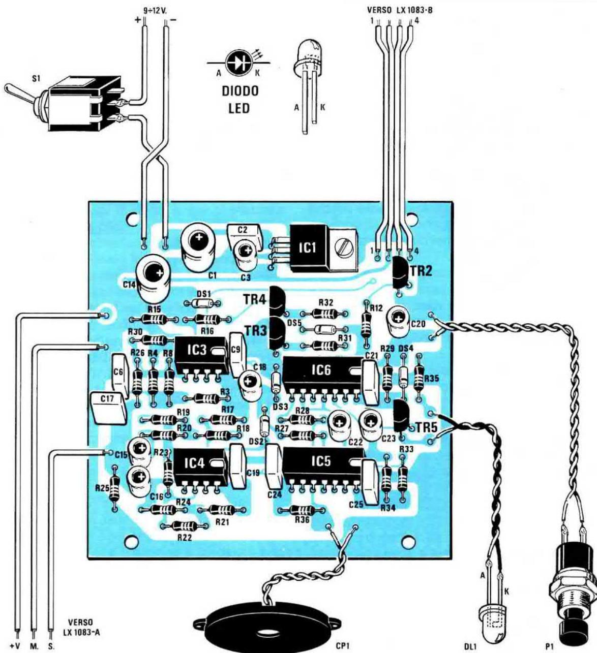
Fig.8 Schema pratico di montaggio della scheda base LX.1083. Attenzione a non invertire i fili 1-2-3-4 della piattina collegandoli alla scheda LX.1083/B (vedi fig.10). Lo stesso dicasi per i tre fili che vanno alla scheda LX.1083/A.
