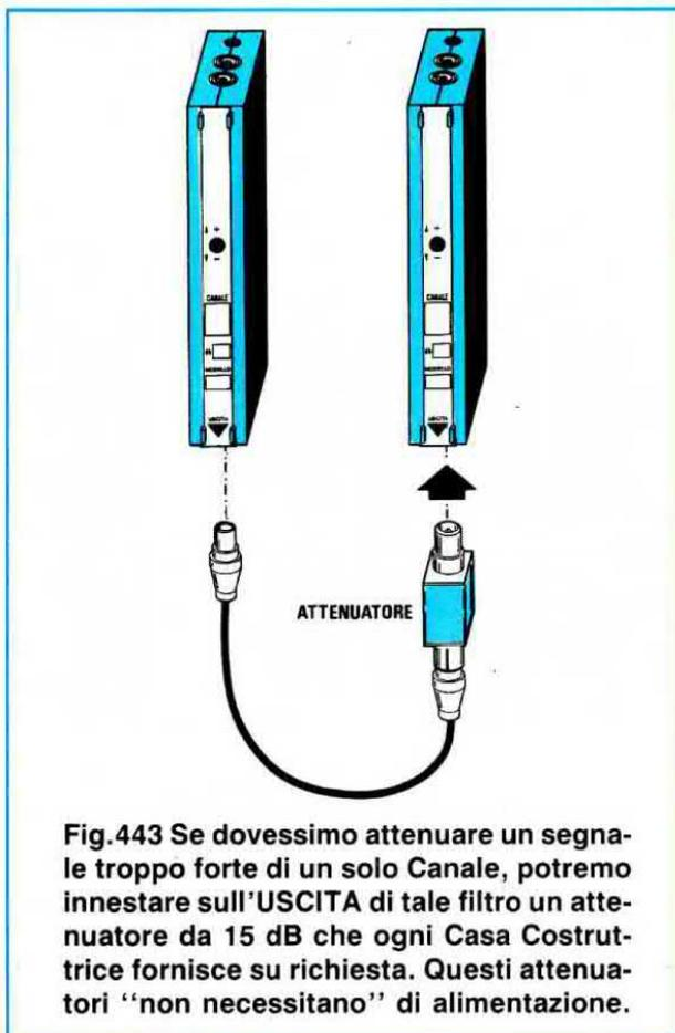
Fig.443 Se dovessimo attenuare un segnale troppo forte di un solo Canale, potremo innestare sull'USCITA di tale filtro un attenuatore da 15 dB che ogni Casa Costruttrice fornisce su richiesta. Questi attenuatori "non necessitano" di alimentazione.
