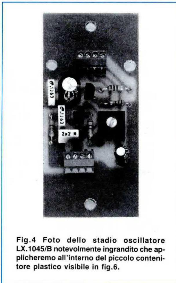
Fig.4 Foto dello stadio oscillatore LX.1045/B notevolmente ingrandito che applicheremo all'interno del piccolo contenitore plastico visibile in fig.6.
