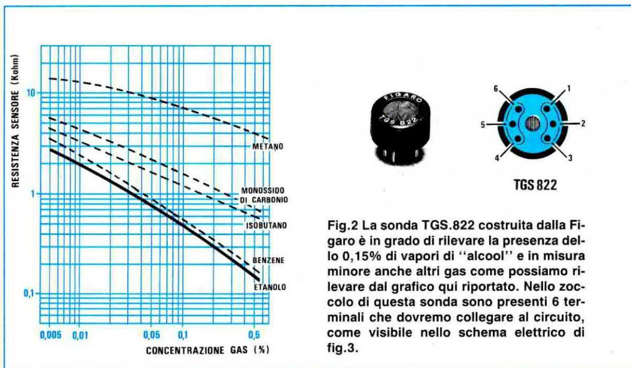
Fig.2 La sonda TGS.822 costruita dalla Figaro è in grado di rilevare la presenza dello 0,15% di vapori di "alcool" e in misura minore anche altri gas come possiamo rilevare dal grafico qui riportato. Nello zoccolo di questa sonda sono presenti 6 terminali che dovremo collegare al circuito, come visibile nello schema elettrico di fig.3.
