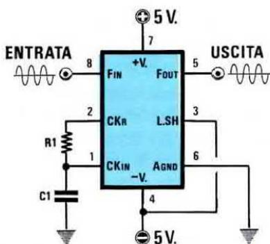
Fig.9 Se alimenterete l'integrato con una tensione "duale", il condensatore C1 e il piedino 6 (A/Gnd) andranno collegati a "massa", mentre il piedino 3 (LSH) andrà necessariamente collegato al piedino 4 della tensione negativa di alimentazione (vedi piedino 4).
