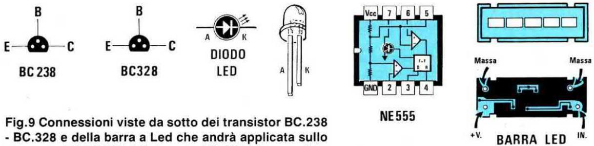
Fig.9 Connessioni viste da sotto dei transistor BC.238 - BC.328 e della barra a Led che andrà applicata sullo stampato LX.1097/B. L'integrato NE.555 è invece visto da sopra.
