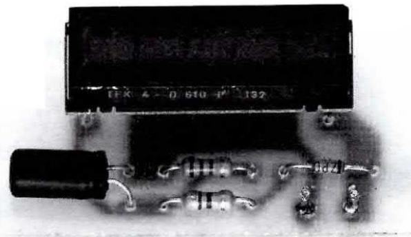
Fig.8 Foto ingrandita del circuito di visualizzazione siglato LX.1097/B.
