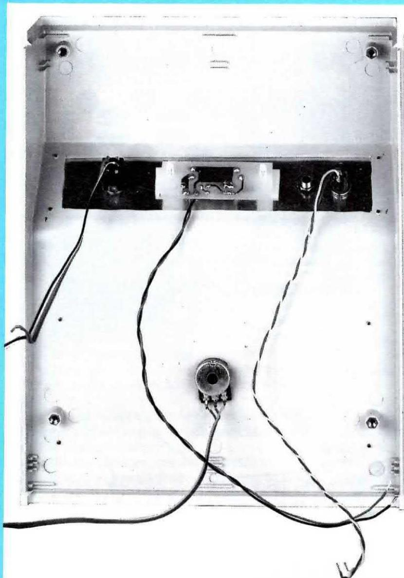
**Fig.14** La bassetta LX.1097/B verrà fissata al pannello in alluminio già forato, con due distanziatori plastici autoadesivi. Nella parte centrale di questo mobile fisseremo anche il potenziometro R10.
