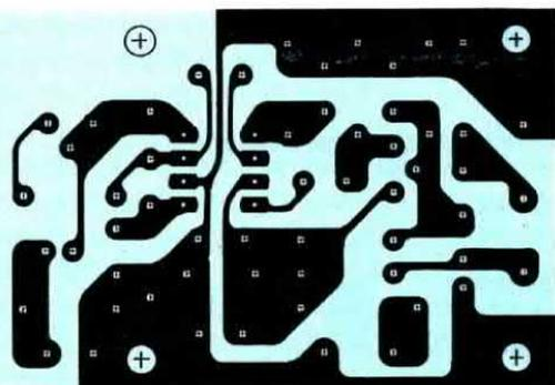
Fig.6 Dimensioni a grandezza naturale del circuito stampato LX.1098 visto dal lato rame. Questo circuito vi verrà fornito forato e completo di disegno serigrafico.
