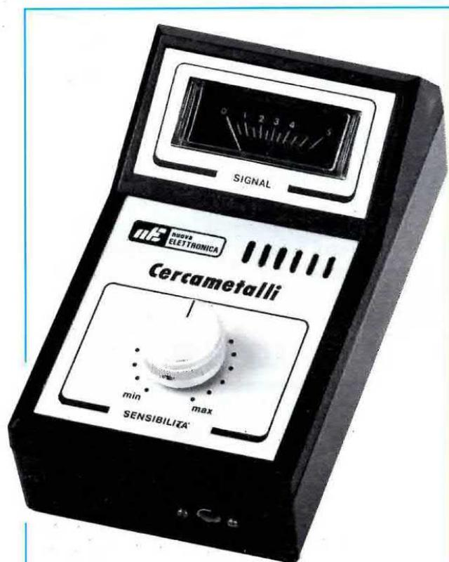
Fig.18 Il mobile plastico verrà fornito di due pannelli metallici già forati e serigrafati, che andranno fissati utilizzando dell'attaccatutto o altri collanti facilmente reperibili in ogni cartoleria o mesticheria.
