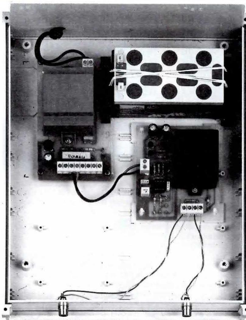
**Fig.13** Per fissare la batteria all'interno del mobile troverete nel kit due squadrette metalliche sagomate. Un elastico agganciato alle due squadrette impedirà alla batteria di muoversi durante il trasporto.
