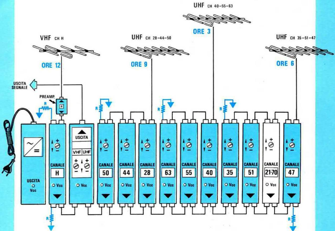
Fig.441 Composta la centralina, innesteremo sul modulo VHF del "Canale H" un Preamplificatore d'antenna da 8-12 dB in modo da aumentare la sua ampiezza, cioè portarla da "65 dBmicrovolt" a circa "73-77 dBmicrovolt".
