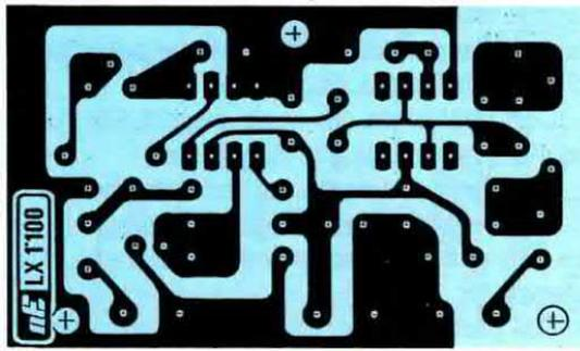
Fig.16 Disegno a grandezza naturale del circuito stampato visto dal lato rame. Utilizzando questo circuito stampato e i due integrati TL.081 e MF4/100 presenti nel kit, potremo realizzare dei filtri con altre diverse frequenza di taglio, modificando solamente i valori di R3-C3-R5-C6-R8-C8.
