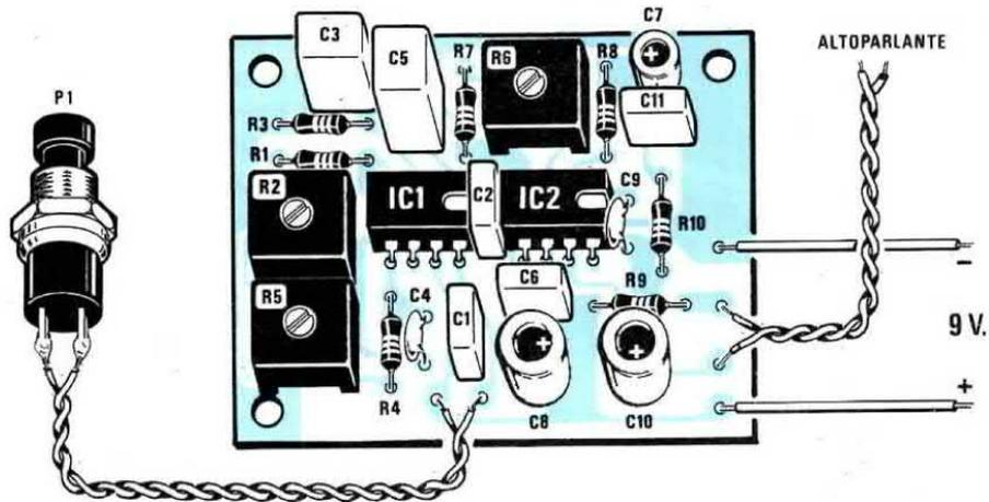
Fig.2 Schema pratico di montaggio del kit LX.1106. Il trimmer R2 serve per variare la velocità di esecuzione, il trimmer R5 per modificare l'ottava ed il trimmer R6 per il volume.
