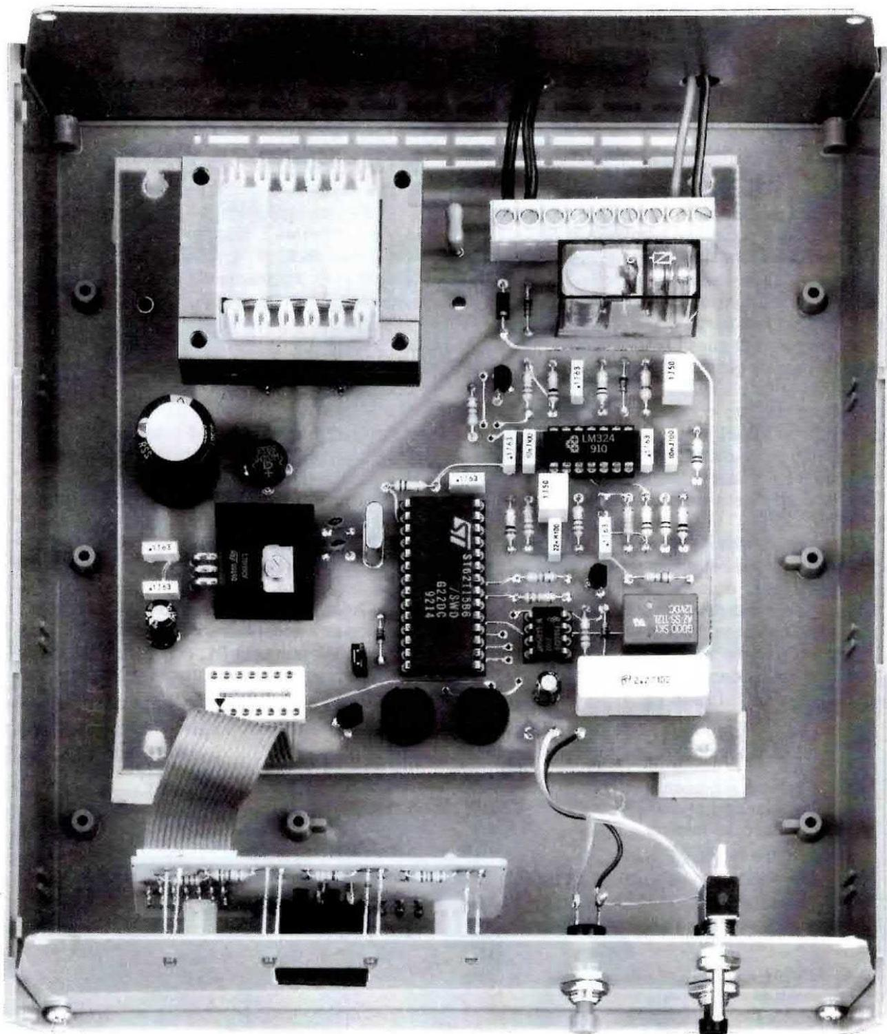
**Fig.13** Per fissare lo stampato LX.1107 sulla base del mobile e LX.1107/B sul pannello frontale, userete i 6 distanziatori plastici autoadesivi che troverete nel kit. Facciamo presente che il pannello frontale NON È forato.
