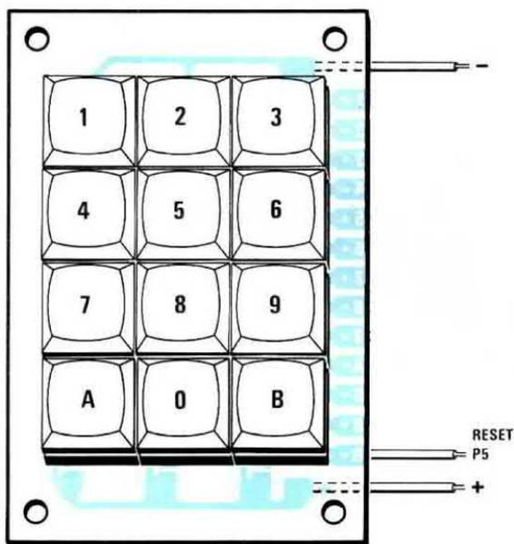
Fig.4 I tre fili -, + e Reset, che escono dalla tastiera, andranno collegati sulle corrispondenti piste presenti sullo stampato di destra. Per impostare il codice vedere gli esempi di figg.8-9.
