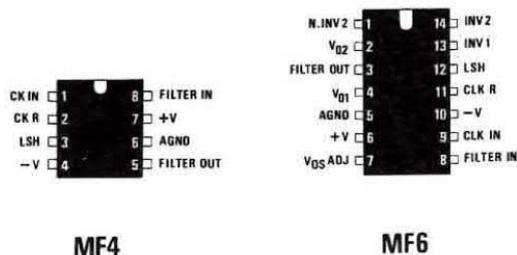
**Fig.1** Piedinatura degli integrati **MF4 - MF6** vista da sopra. Con gli integrati della serie **MF4** potremo realizzare dei filtri Passa/Basso con una attenuazione di **24 dB x ottava**, mentre con quelli della serie **MF6** potremo realizzare dei filtri con una attenuazione di **36 dB x ottava**.
