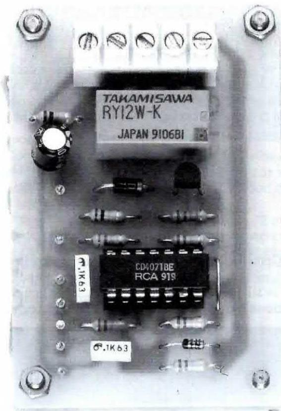
**Fig.2** In questa foto, notevolmente ingrandita, potrete vedere come si presenterà il vostro circuito a montaggio ultimato. Si noti sulla destra dell'integrato CD.4071 il "ponticello" da effettuare con uno spezzone di filo di rame nudo.
