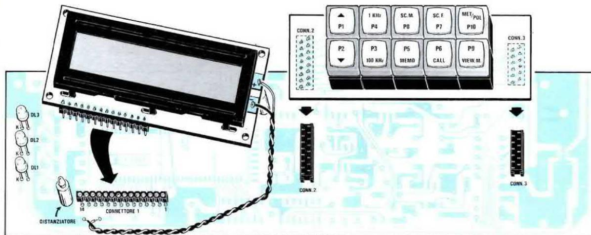
Fig.18 Rivoltando lo stampato LX.1095, inseriremo nei due connettori indicati CONN2-CONN3 la tastiera e nel CONN1 il display LCD. Non dimenticate di collegare le due piste +/- visibili sulla destra del display ai due fili che andranno collegati allo stampato rispettando la polarità. Vedi in fig.17 i due fili in alto a sinistra indicato "Al Display".
