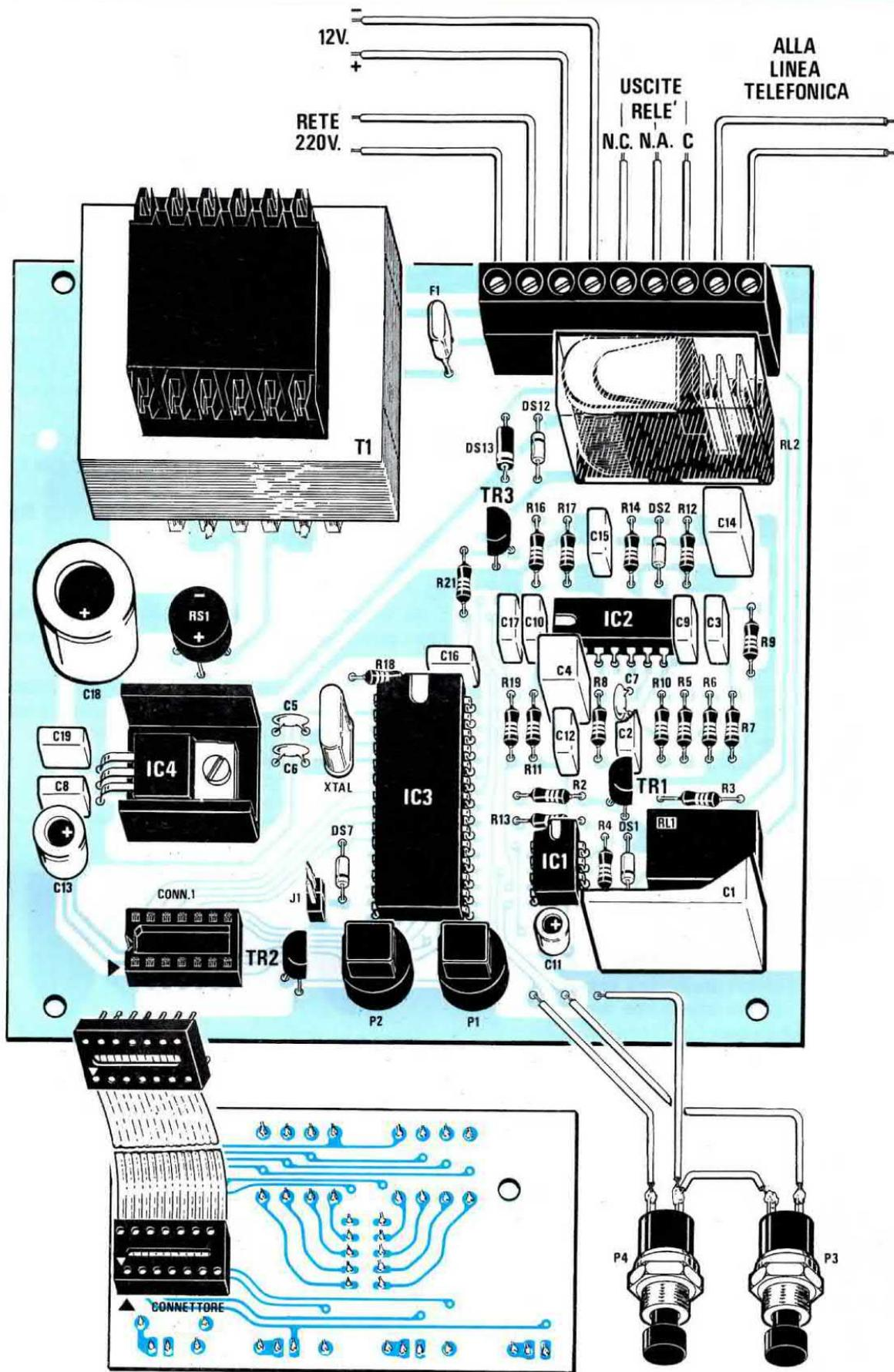
è da escludere infatti che in fase di montaggio vengano eseguite delle saldature difettose o si invertano i fili sui due commutatori oppure venga posto il commutatore di destra sulla sinistra, ottenendo involontariamente il codice **6-3** invece del codice **3-6**.
