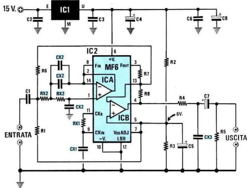
Fig.5 Schema elettrico di un filtro Notch con MF6 completo di filtro "anti-immagine". I valori delle resistenze siglate RX e dei condensatori siglati CX andranno scelti in base alla frequenza di taglio.
