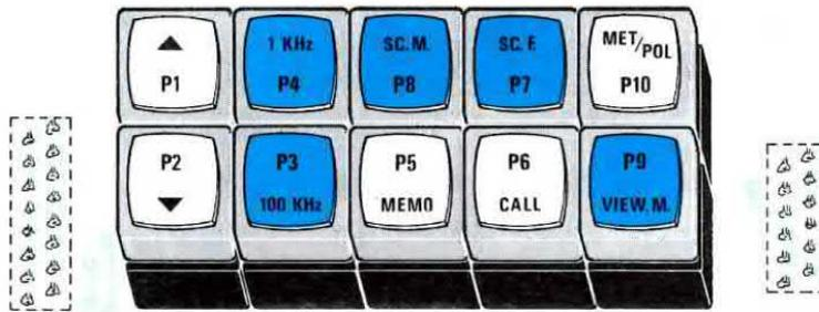
Fig.20 Lo stesso stampato visto dal lato pulsanti. All'interno dei pulsanti colorati risulta inserito un diodo led (vedi Fig.23).
