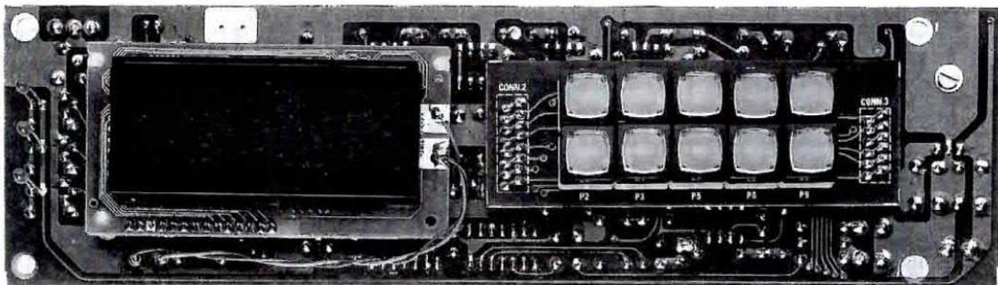
**Fig.10** Come si presenterà la scheda LX.1095 completa di tastiera e di display. Per tener bloccato il display allo stampato utilizzeremo tre piccoli distanziatori plastici.
