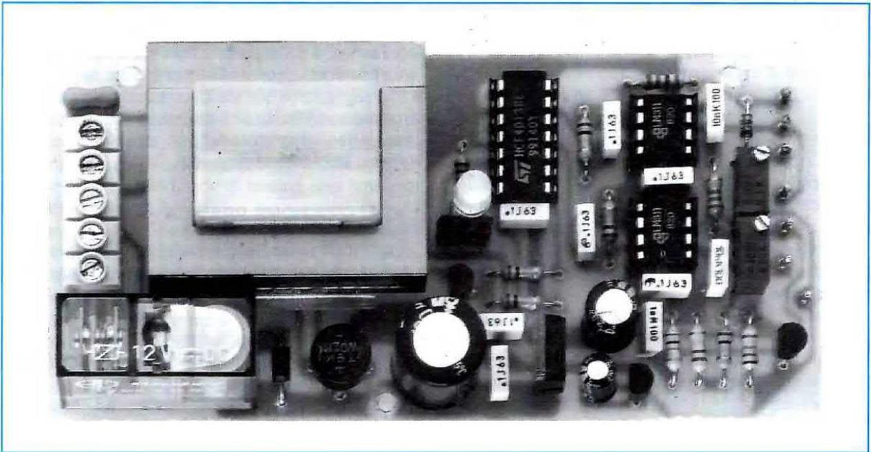
**Fig.7 Foto del termostato. Prima di fissare i due trimmer multigiri R3-R8 consigliamo di ruotare le loro viti in modo da portare il cursore a metà corsa. Notate dalla foto che la sonda LM.35 è stata stagnata direttamente sullo stampato.**
