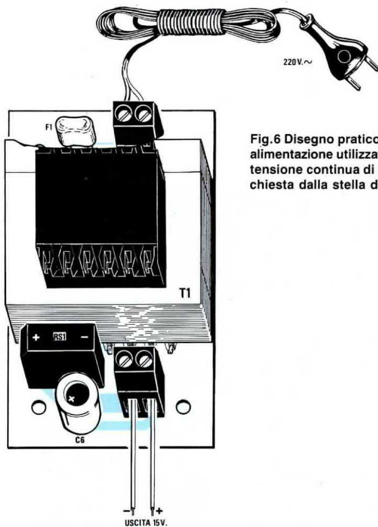
Fig.6 Disegno pratico dello stadio di alimentazione utilizzato per fornire la tensione continua di circa 15 volt richiesta dalla stella di Natale.
