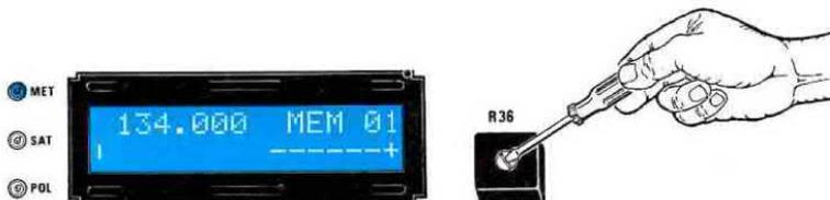
Fig.36 In assenza del segnale Meteosat ruotate il trimmer R36 fino a far apparire sull'S-Meter una sola barra.
