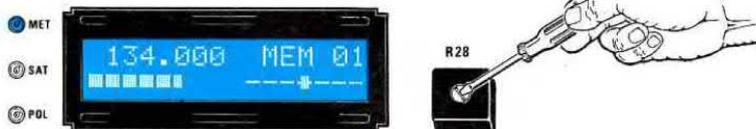
Fig.35 Ruotate il trimmer R28 a metà corsa, poi il nucleo della MF3 fino a portare la "barra" dell'AFC al centro scala.
