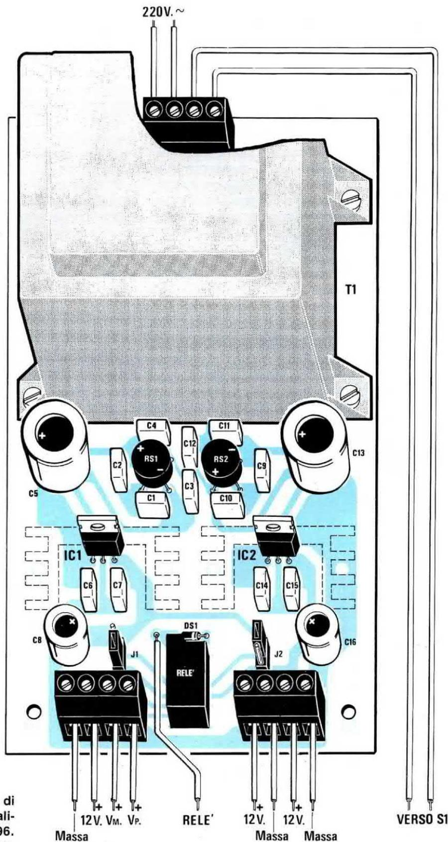
Fig. 24 Schema pratico di montaggio dello stadio alimentatore siglato LX.1096. Il fusibile F1 di rete è inserito nella vaschetta della "presa rete".
