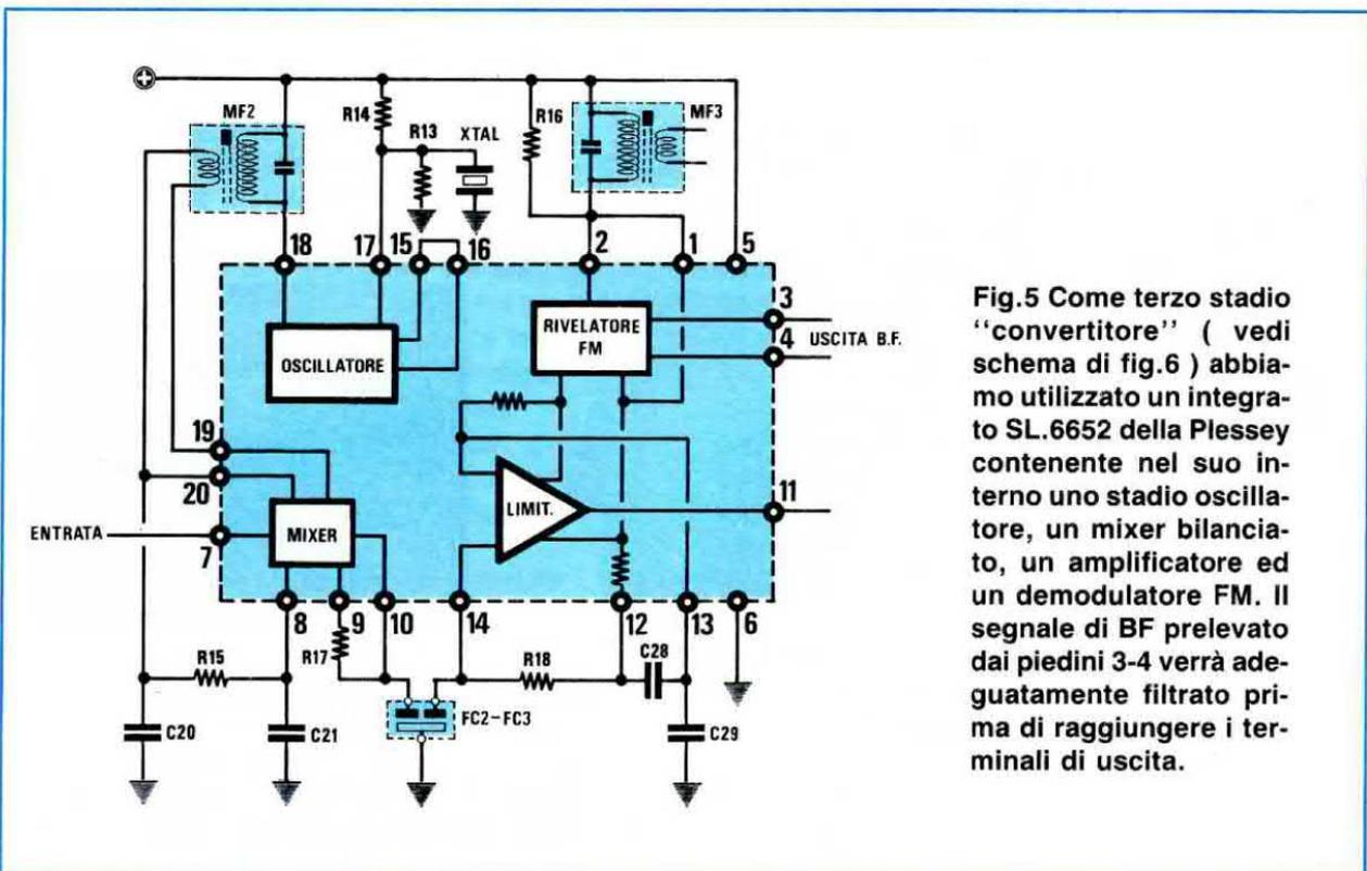
**Fig.5** Come terzo stadio "convertitore" ( vedi schema di fig.6 ) abbiamo utilizzato un integrato **SL.6652** della Plessey contenente nel suo interno uno stadio oscillatore, un mixer bilanciato, un amplificatore ed un demodulatore FM. Il segnale di BF prelevato dai piedini 3-4 verrà adeguatamente filtrato prima di raggiungere i terminali di uscita.
