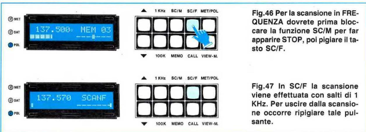
Fig.46 Per la scansione in FREQUENZA dovreste prima bloccare la funzione SC/M per far apparire STOP, poi pigiare il tasto SC/F.
