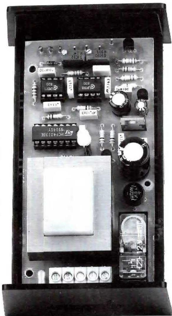
**Fig.1** Foto dello stampato LX.1102 inserito all'interno del suo mobile plastico. Si noti in basso il relè e la morsettiera per l'alimentazione a 220 volt e per l'uscita del relè. Il potenziometro di regolazione verrà fissato sul coperchio del mobile.
