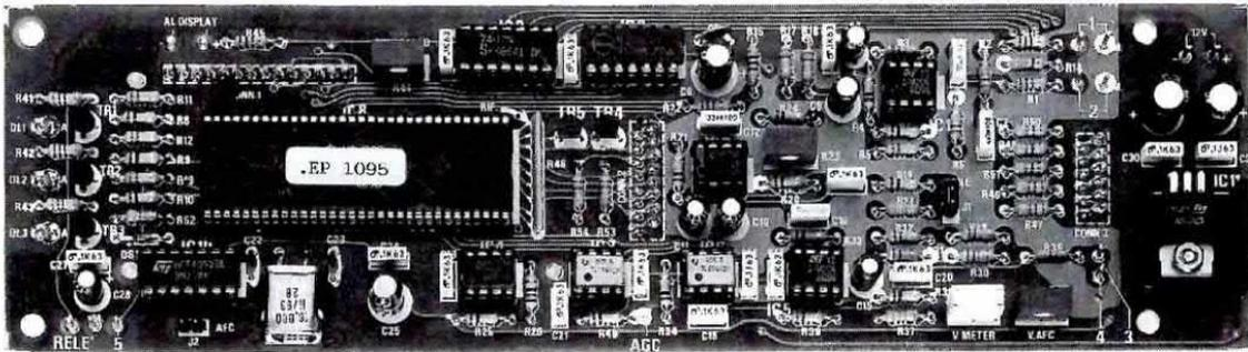
**Fig.8** Foto della scheda LX.1095 vista dal lato componenti. Si noti il corpo del quarzo staginato sulla pista in rame e l'integrato uA.7805 (IC11) montato sopra l'aletta di raffreddamento.
