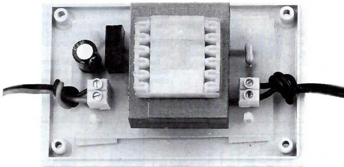
Fig.5 L'alimentatore verrà racchiuso entro un mobile plastico per evitare che qualche bimbo possa toccare i fili di rete a 220 volt.
