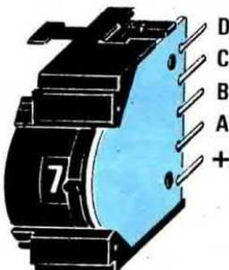
**Fig.7** Quando innesterete i due commutatori binari sul circuito stampato ( vedi figg.8-10 ) controllate che i numeri appaiano dritti ( vedi fig.8 - 10 ). Consigliamo di stagnare i terminali sullo stampato solo dopo aver fissato il circuito sul pannello frontale del mobile ( vedi fig.13 ).
