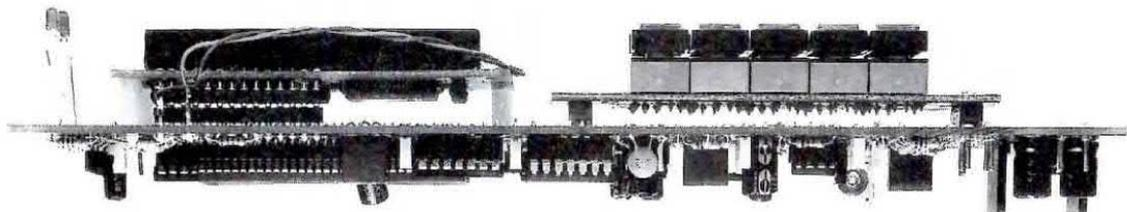
**Fig.11** Foto della scheda LX.1095 vista di lato. Notate i distanziatori plastici utilizzati per tenere bloccato il display e i tre diodi led non molto visibili nella precedente foto.
