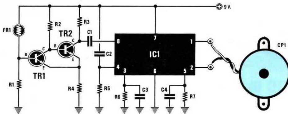
Fig.1 Schema elettrico del progetto, piedinatura del transistor BC.547 visto da sotto e dell'integrato LS.3404 visto da sopra.
