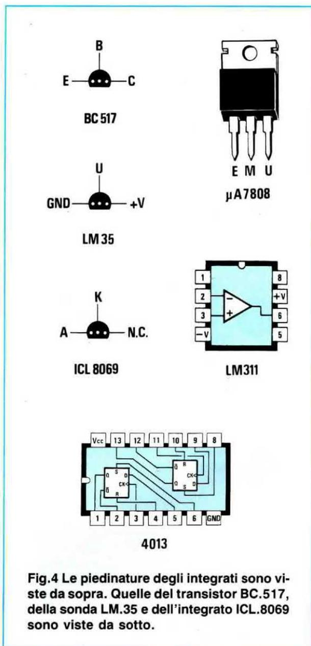
Fig.4 Le piedinature degli integrati sono viste da sopra. Quelle del transistor BC.517, della sonda LM.35 e dell'integrato ICL.8069 sono viste da sotto.
