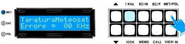
Fig.31 Ripigiando il tasto MET/POL sul display apparirà la scritta "Taratura Meteosat - Errore 00 KHz"
