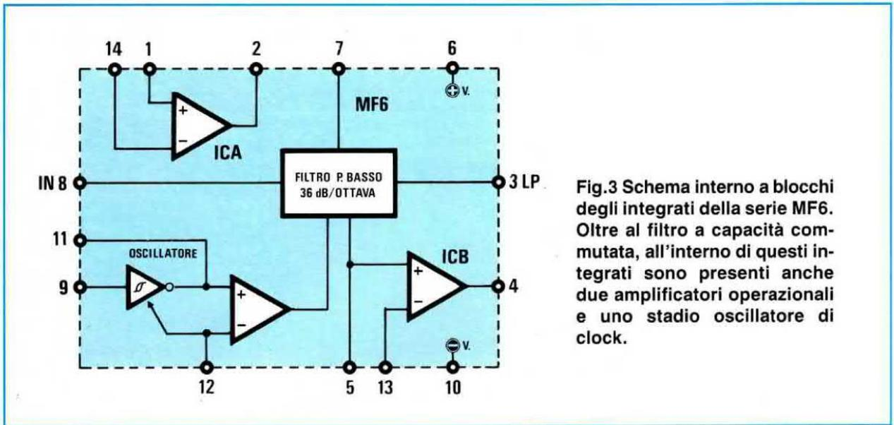
Fig.3 Schema interno a blocchi degli integrati della serie MF6. Oltre al filtro a capacità commutata, all'interno di questi integrati sono presenti anche due amplificatori operazionali e uno stadio oscillatore di clock.
