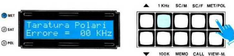
Fig.32 Pigiando ancora una volta apparirà "Taratura Polari" e a questo punto la taratura sarà completata.
