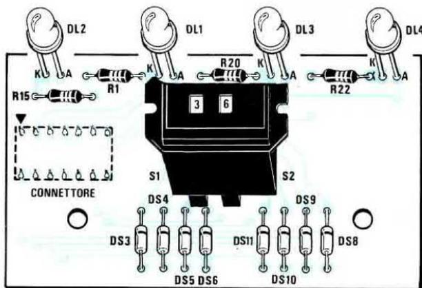
Fig.10 Schema pratico di montaggio della scheda LX.1107/B. Su tale montaggio dovremo rispettare la polarità dei diodi al silicio e quella dei diodi led. Notate le lettere A-K ai due lati dei diodi led.
