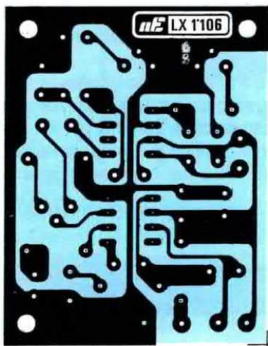
Fig.4 Disegno del circuito stampato a grandezza naturale visto dal lato rame.
