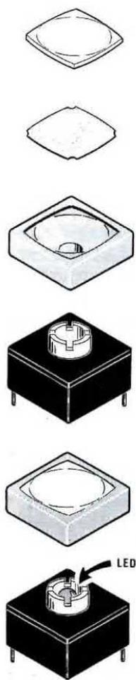
Fig. 23 I pulsanti visibili nelle figg. 20-21 sono composti di quattro parti. Solo in cinque di essi è presente all'interno un diodo led.
