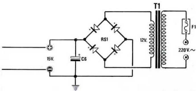
Fig.4 Schema elettrico della stella di Natale. Potremo alimentare questo circuito con una tensione continua compresa tra 12-16 volt che potremo prelevare da un qualsiasi alimentatore o dal circuito visibile nelle figg.5-6.
