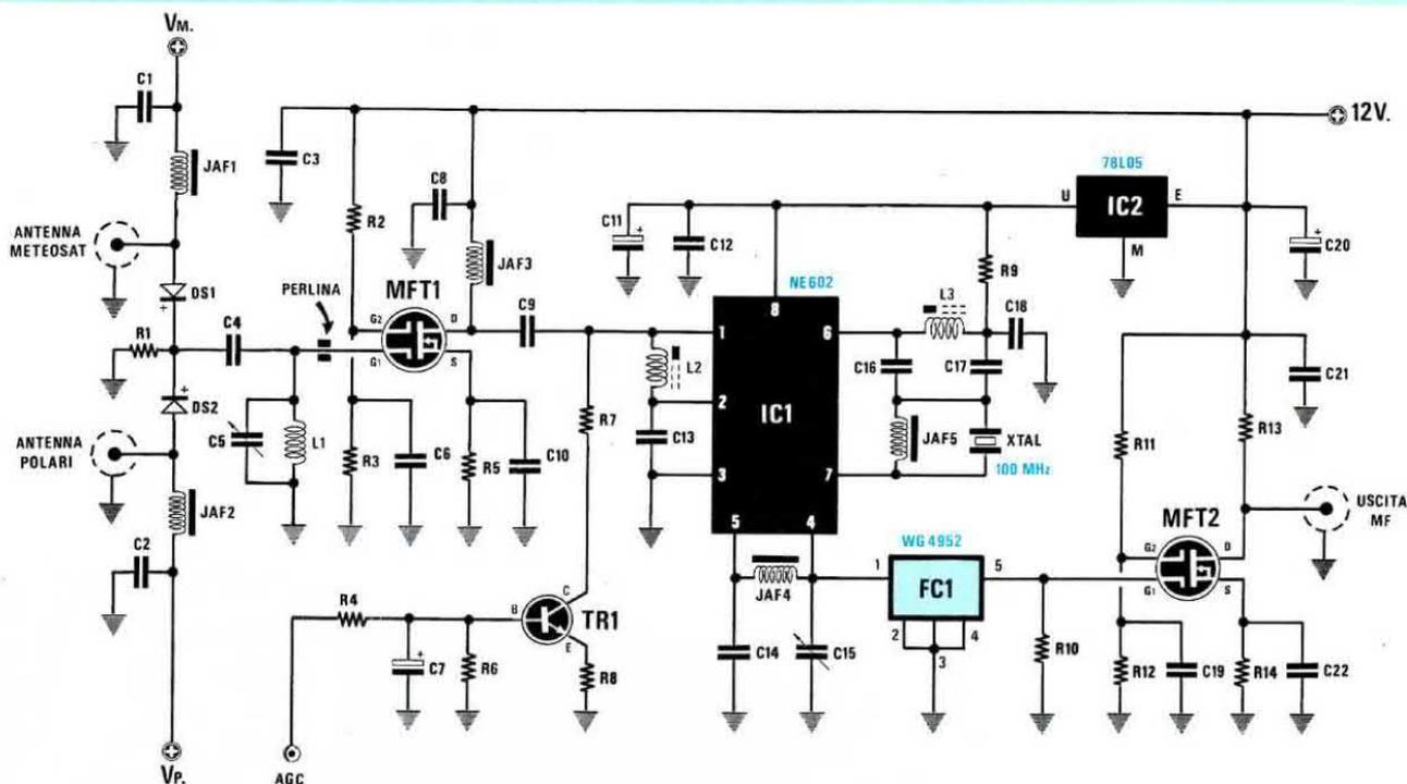
**Fig.1** Schema elettrico dello stadio d'ingresso e prima conversione da 132-140 MHz a 32-40 MHz che vi verrà fornito già montato e tarato ( vedi Fig.3 ) In fase di taratura il nostro laboratorio modificherà, se necessario, dei valori di resistenze o di capacità in modo da ottenere il massimo rendimento.
