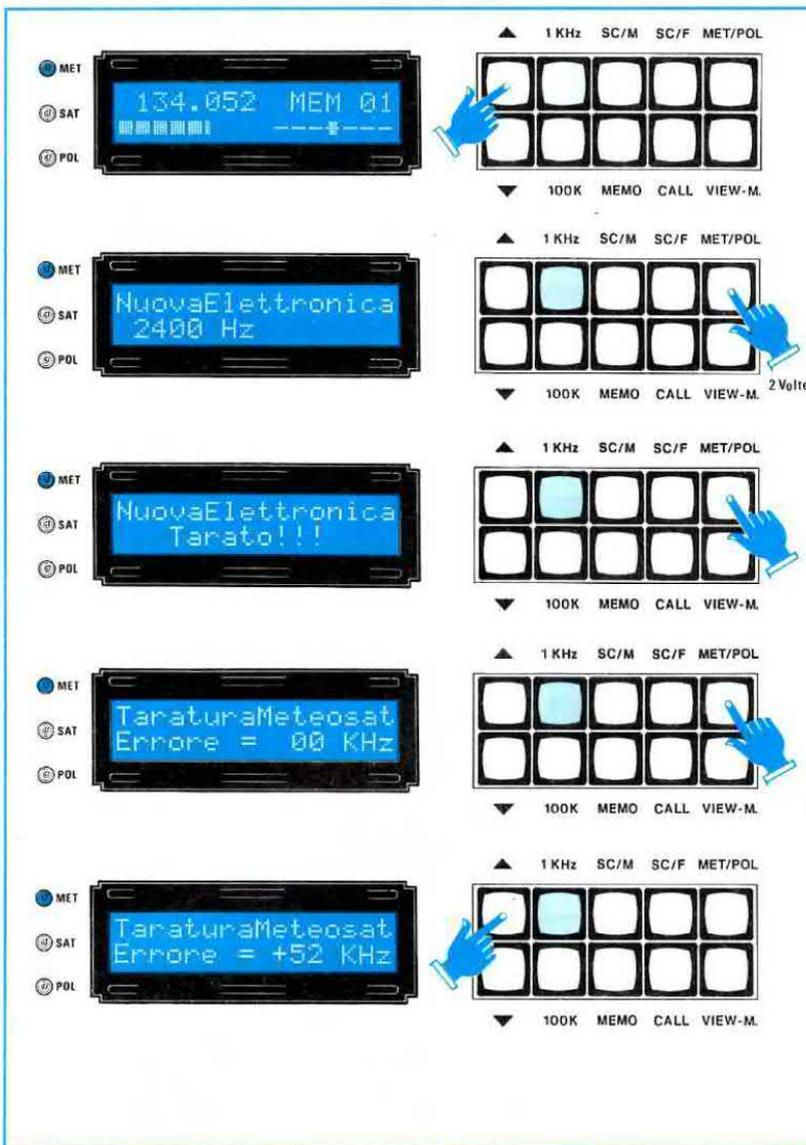
Fig.38 Se il ricevitore si auto-sintonizzerà sui 134.052 KHz potremo correggere questo errore nel modo che ora vi spiegheremo.
