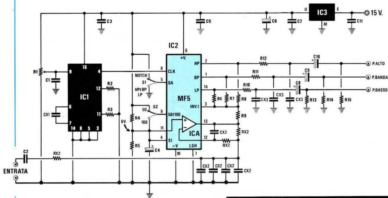
Fig.13 Schema elettrico di un filtro Universale che utilizza un integrato MF5. Se il deviatore S1 viene posto su Notch, l'integrato ci fornirà il filtro Notch, mentre se posto su HP-BP-LP ci potrà fornire il Passa/Alto - Passa/Basso e Passa/Banda ma non il Notch. Il deviatore S2 serve per dividere la frequenza di "clock" per 50 o per 100. Il trimmer R1 serve per tarare con precisione la frequenza di taglio.
