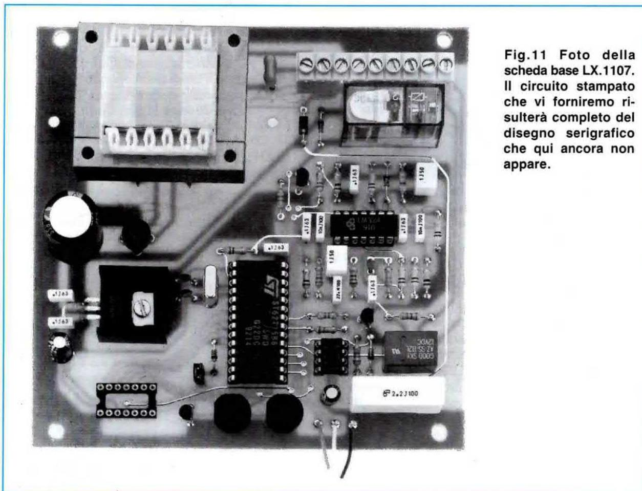
Fig.11 Foto della scheda base LX.1107. Il circuito stampato che vi forniremo risulterà completo del disegno serigrafico che qui ancora non appare.
