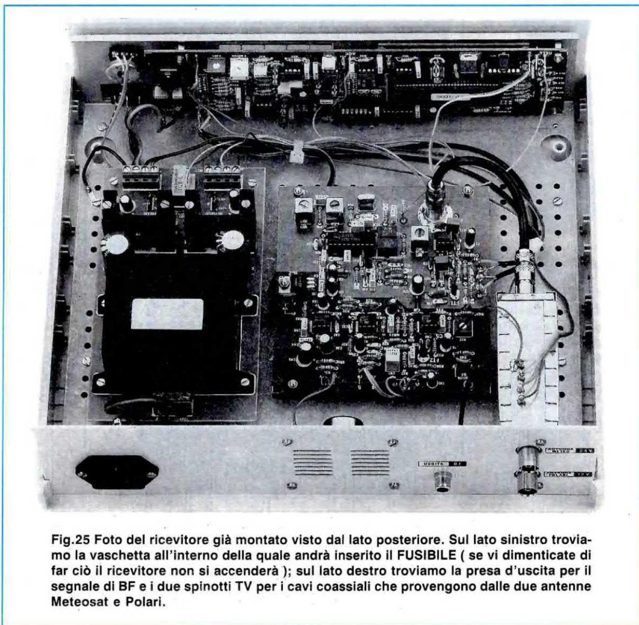
**Fig.25** Foto del ricevitore già montato visto dal lato posteriore. Sul lato sinistro troviamo la vaschetta all'interno della quale andrà inserito il **FUSIBILE** ( se vi dimenticate di far ciò il ricevitore non si accenderà ); sul lato destro troviamo la presa d'uscita per il segnale di BF e i due spinotti TV per i cavi coassiali che provengono dalle due antenne Meteosat e Polari.
