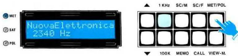
Fig.28 Per tarare sui 2.400 Hz occorre tener pigiato il pulsante MET/POL dopodichè si potrà accendere il ricevitore.
