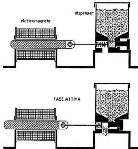
Anche se nello schema elettrico è stato inserito un relè, si consiglia di sostituirlo con una elettrocalamita che potremo togliere da una vecchia apriporta elettrica. Il pistone di questa elettrocalamita verrà utilizzato per aprire lo sportellino del dosatore. Si consiglia di fissare molto bene il dosatore sull'acquario e di utilizzare soltanto mangime granulare.
