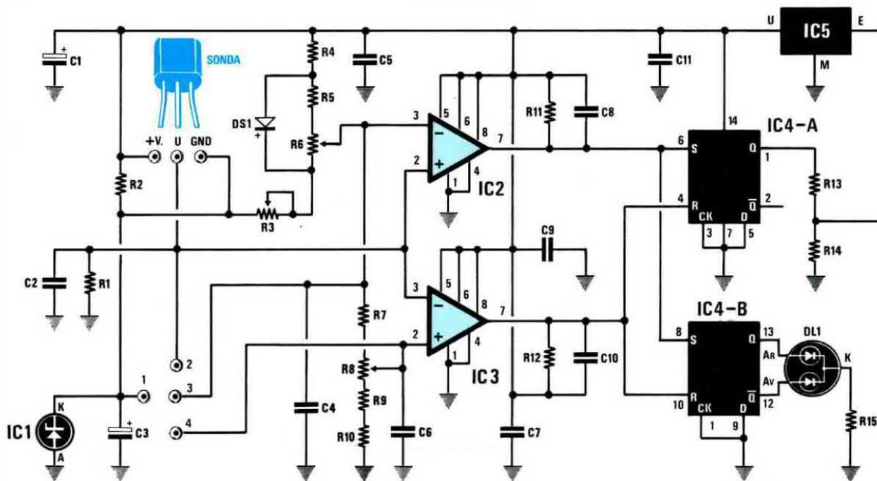
Fig.2 Schema elettrico del termostato. I terminali visibili in basso a sinistra indicati con i numeri 1-2-3-4 ci serviranno per controllare a quale temperatura si ecciterà o disecciterà il relè.
