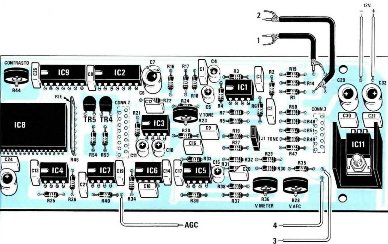
Fig.17 Schema pratico di montaggio della scheda LX.1095. Per la rete resistiva R46 il punto di riferimento va rivolto verso IC9. Facciamo presente che sul connettore AFC-J2 lo spinnotto di cortocircuito va inserito solo in fase di taratura.
