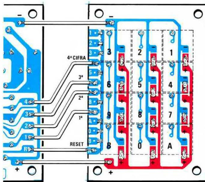
Fig.9 In questo disegno vi riportiamo un esempio di come dovrete collegare, con una goccia di stagno, i terminali centrali dei vari numeri ai terminali negativi ( blu ) ed ai terminali positivi ( rossi ) per ottenere il codice 9B14. Con le piste già collegate per questo codice, potremo ottenere altri codici, ad esempio 1B94 - B941 - 914B - 49B1 ecc., se salderemo sugli stessi numeri, ma con un diverso ordine, i fili 1-2-3-4 che partono dallo stampato LX.1104.
