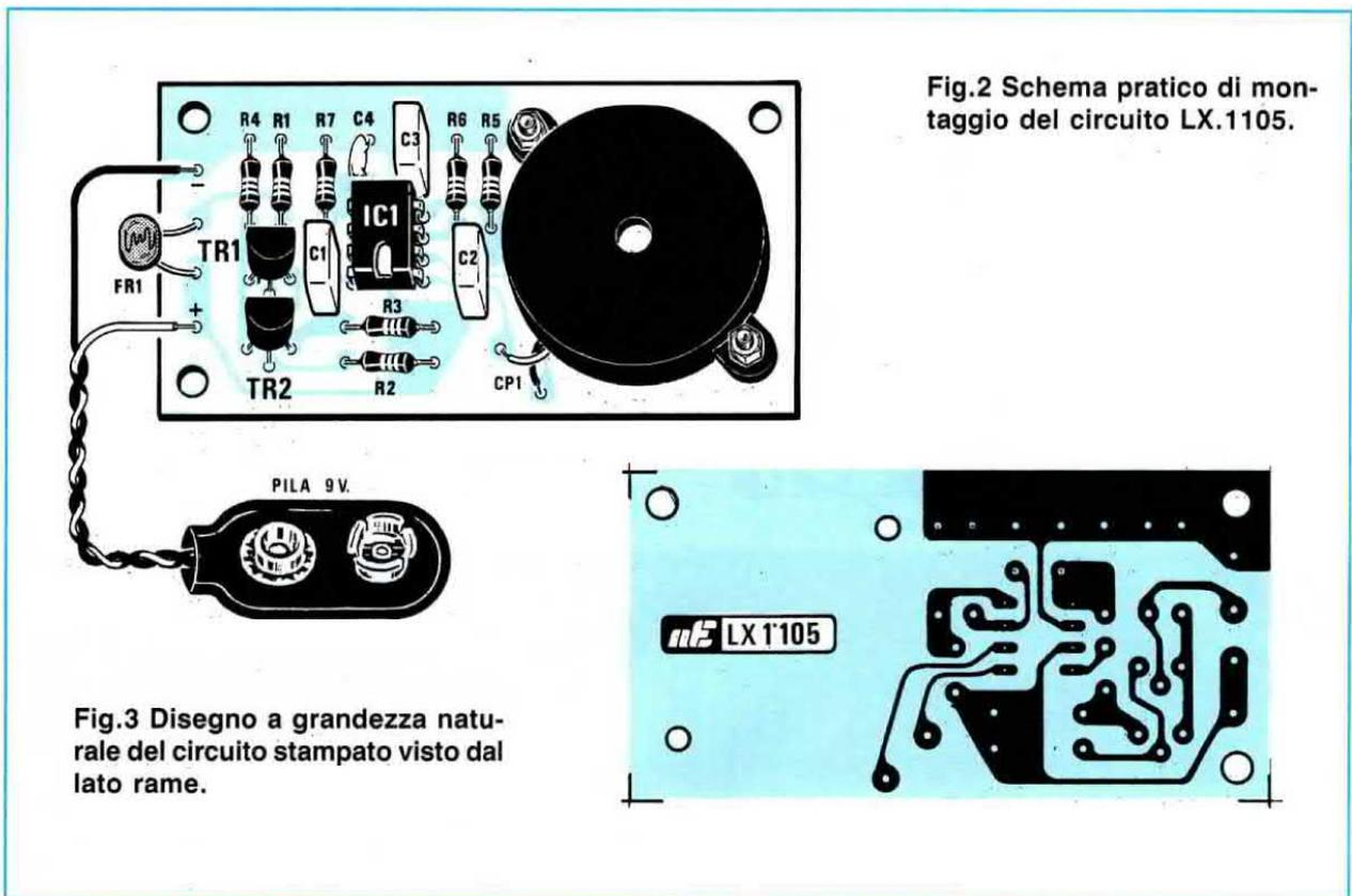
Fig.2 Schema pratico di montaggio del circuito LX.1105.
