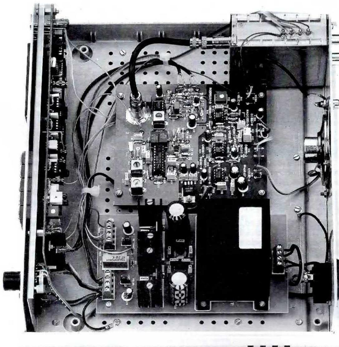
**Fig.43** Quando fisserete le basette del circuito stampato sul ricevitore non dimenticatevi di utilizzare le torrette distanziatrici per evitare che la parte sottostante del circuito stampato tocchi il metallo del piano di sostegno.
