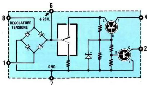
Fig.3 All'interno dell'integrato PSB.6620, utilizzato nel nostro telecomando come rivelatore di squilli, è presente un ponte raddrizzatore, un commutatore elettronico e due transistor d'uscita.
