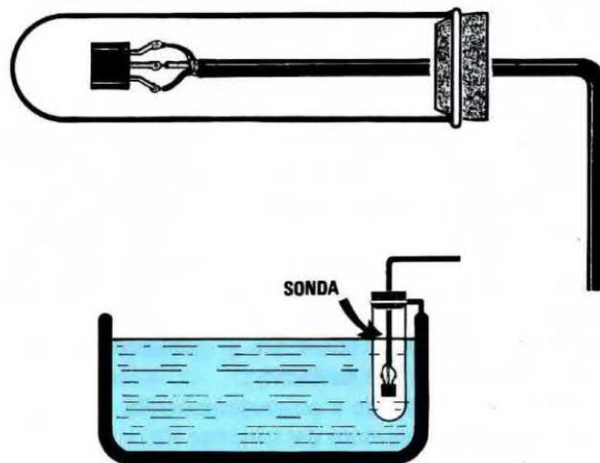
Fig.8 Se dovrete usare la sonda per controllare la temperatura di liquidi, conviene inserirla dentro una provetta in vetro o plastica sigillando l'estremità superiore con stucco per vetri o con silicone.
