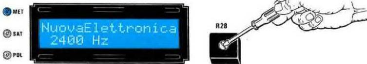
Fig.29 A questo punto si ruoterà il trimmer R23 fino a leggere sul display 2.400 Hz. È ammessa una tolleranza di 10-16 Hz.
