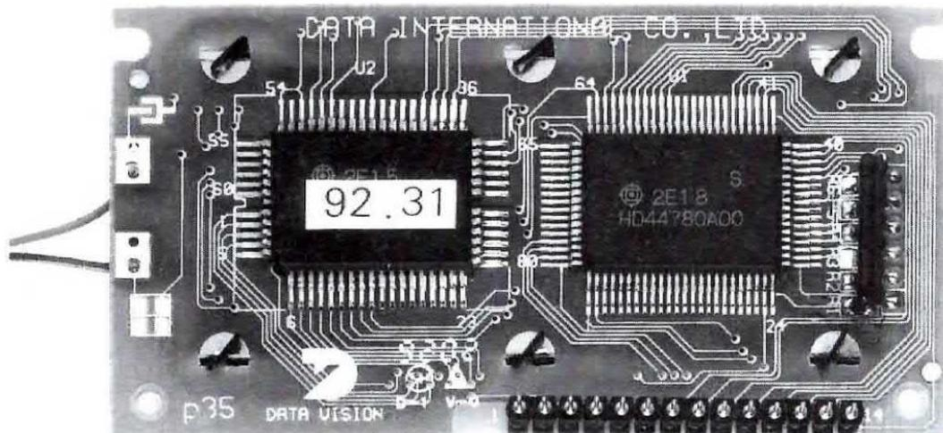
Fig.22 Sul retro del display LCD troviamo già inseriti due microprocessori che provvederanno a pilotare tramite un programma la matrice a punti. Su tale display dovrete soltanto stagnare il connettore maschio a 14 piedini che troverete nel kit. Nella foto questo connettore è visibile in basso sul lato destro.
