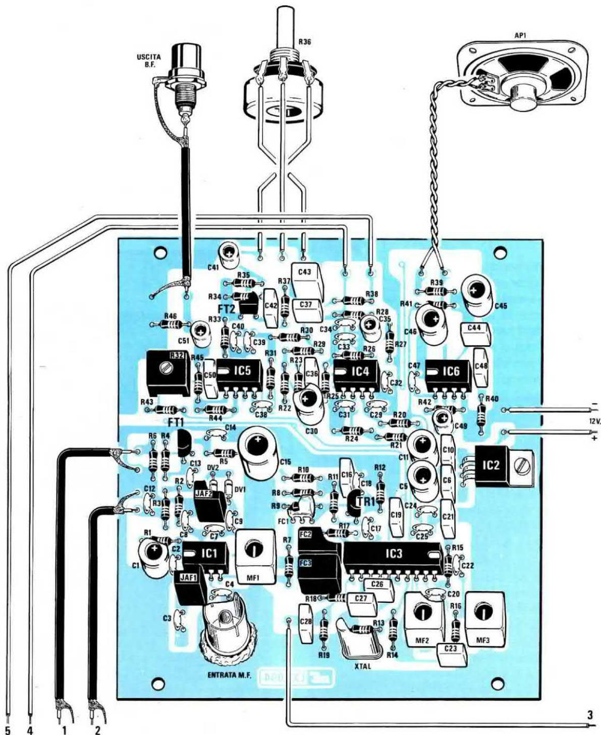
Fig.15 Schema pratico di montaggio della scheda LX.1094. **IMPORTANTE** = Il condensatore C8 va fissato in parallelo ad una resistenza da 1.000 ohm, come visibile nel disegno posto qui a destra. Nel disegno dello schema pratico questa modifica non appare ( vedi C8 posto tra IC1 e JAF2 ). Dovremo collegare i fili numerati 5-4-3 e i cavetti schermati con 1-2 alla scheda di fig.17.
