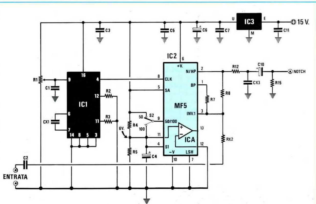
Fig. 14 Chi utilizzerà l'integrato MF5 per realizzare dei soli filtri Notch, potrà togliere dallo schema di fig.13 molti componenti superflui. In questo schema non abbiamo volutamente inserito il filtro "anti-immagine".
