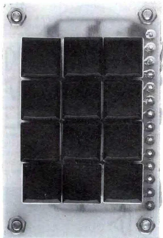
**Fig.3** Sul secondo stampato inseriremo i 12 tasti presenti nel kit. Poiché i cappucci di questi tasti vengono forniti senza numeri o lettere, consigliamo di acquistare presso una cartoleria dei numeri o lettere autadesive.
