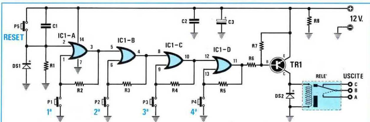
Fig.1 Schema elettrico della chiave elettronica. Nello schema pratico il pulsante P5 di reset è sostituito da 8 pulsanti che verranno collegati tutti in parallelo.
