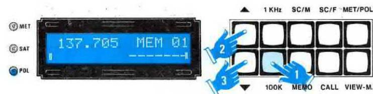
Fig.52 Per modificare una frequenza di centinaia di KHz occorrerà pigiare il tasto 100K poi i tasti P1 e P2.
