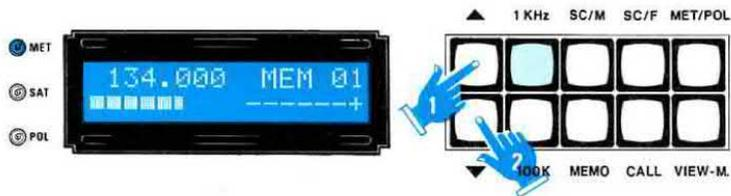
Fig.34 Per tarare la MF3 dovrete pigiare i tasti P1 - P2 fino a far deviare verso il suo massimo le "barre" dell'S-Meter.
