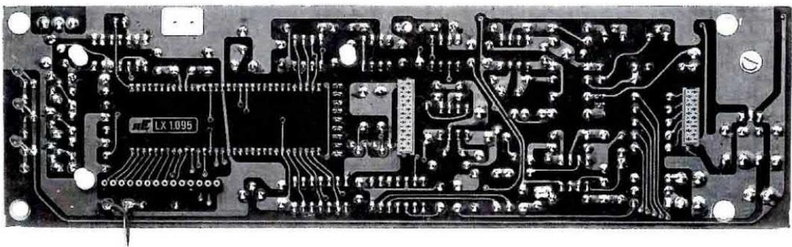
**Fig.9** Foto della stessa scheda vista dal lato opposto. Su tale lato andranno inseriti i due connettori per la tastiera, quello per il display LCD e i tre diodi led appena visibili sulla sinistra.
