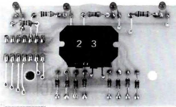
Fig.8 Foto dello stampato LX.1107/B con sopra già fissati i due commutatori binari completi di sponde laterali e dei 4 diodi led. Tenendo lo stampato come visibile in questa foto i numeri li dovreste leggere dritti.
