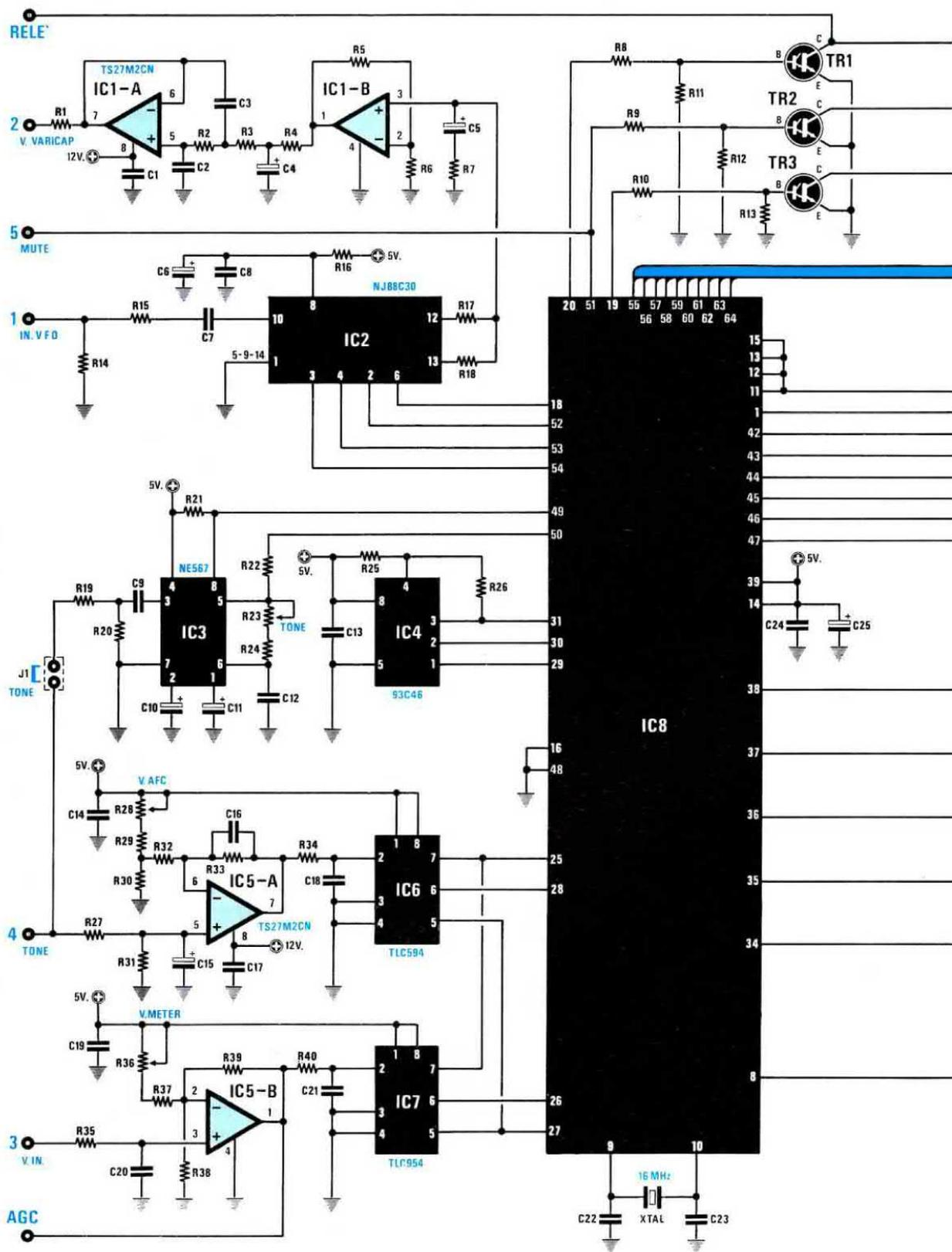
Fig.7 Schema elettrico dello stadio LX.1095. La lista componenti è riportata alla pag. 15 I numeri riportati sui terminali di sinistra andranno a congiungersi allo schema di Fig.6. Il terminale indicato "relè" andrà a collegarsi sullo schema di Fig.12 e quello indicato AGC sul gruppo LX.1093 ( vedi fig.26 ).
