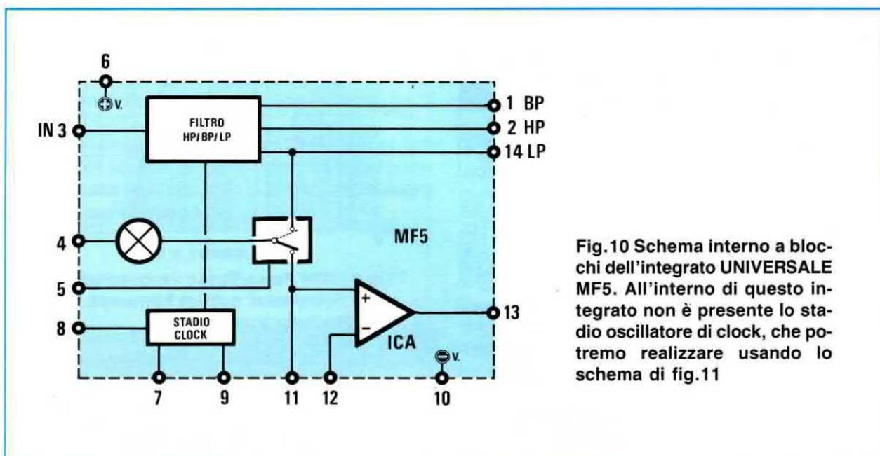
Fig.10 Schema interno a blocchi dell'integrato UNIVERSALE MF5. All'interno di questo integrato non è presente lo stadio oscillatore di clock, che potremo realizzare usando lo schema di fig.11
