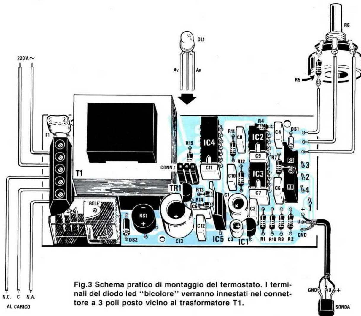
Fig.3 Schema pratico di montaggio del termostato. I terminali del diodo led "bicolore" verranno innestati nel connettore a 3 poli posto vicino al trasformatore T1.
