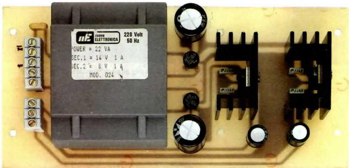
**Fig.33** Foto dello stadio di alimentazione siglato LX.1122. Questo stampato andrà fissato sul coperchio del mobile con delle viti filettanti (vedi fig.37). Nella prima morsettiere posta in alto entrerà la tensione di rete dei 220 volt e dalla morsettiere a 3 poli preleverete le due tensioni stabilizzate (vedi fig.36).
