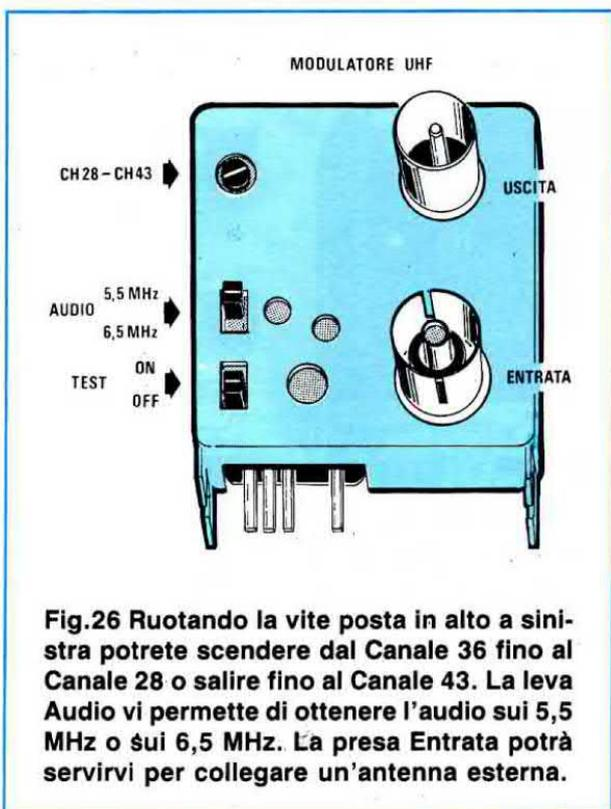
**Fig.26** Ruotando la vite posta in alto a sinistra potrete scendere dal Canale 36 fino al Canale 28 o salire fino al Canale 43. La leva Audio vi permette di ottenere l'audio sui 5,5 MHz o sui 6,5 MHz. La presa Entrata potrà servirvi per collegare un'antenna esterna.
