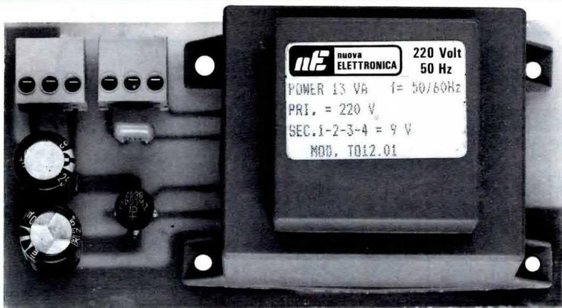
**Fig.14** Come si presenta a montaggio ultimato lo stadio di alimentazione che dovrete poi collocare in posizione verticale all'interno del mobile plastico come visibile nella foto di fig.10. Non dimenticatevi di fissare il trasformatore sulla stampato con le quattro viti.
