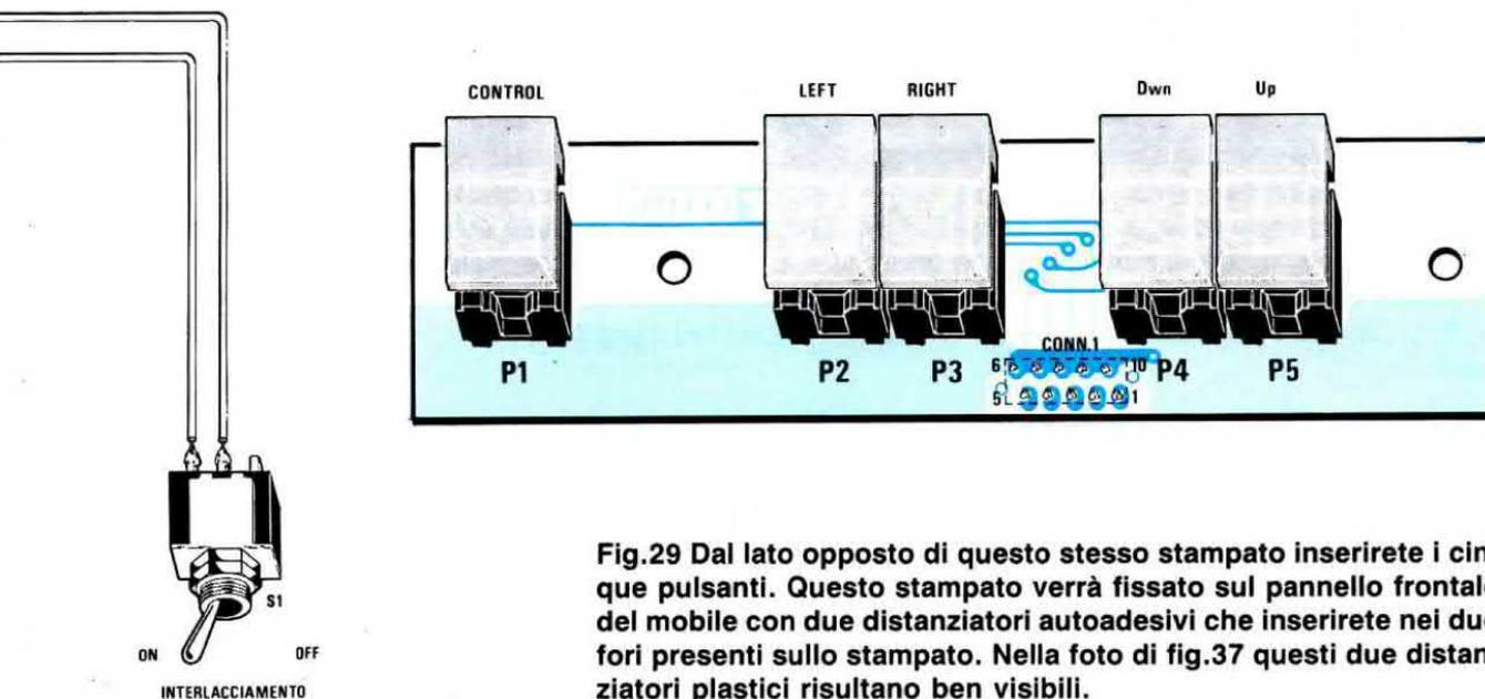
Fig.29 Dal lato opposto di questo stesso stampato inserirete i cinque pulsanti. Questo stampato verrà fissato sul pannello frontale del mobile con due distanziatori autoadesivi che inserirete nei due fori presenti sullo stampato. Nella foto di fig.37 questi due distanziatori plastici risultano ben visibili.
