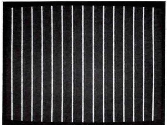
Fig.5 Le linee verticali in bianco/nero servono per controllare la linearità e la focalizzazione in senso verticale. Le righe devono apparire tutte parallele e non sfocate.
