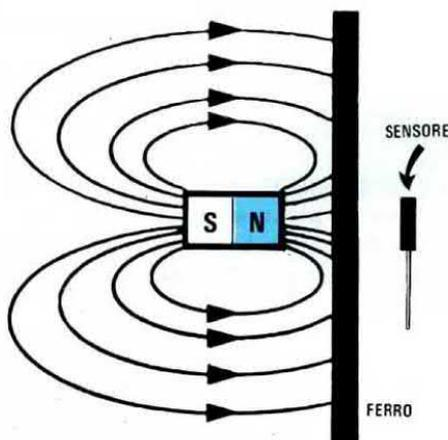
**Fig.12** Applicando tra il magnete ed il sensore un pezzo di ferro, il flusso magnetico non potrà raggiungere la parte "sensibile" del sensore quindi ci indicherà 0 Gauss.
