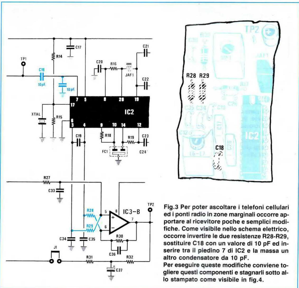
Fig.3 Per poter ascoltare i telefoni cellulari ed i ponti radio in zone marginali occorre apportare al ricevitore poche e semplici modifiche. Come visibile nello schema elettrico, occorre invertire le due resistenze R28-R29, sostituire C18 con un valore di 10 pF ed inserire tra il piedino 7 di IC2 e la massa un altro condensatore da 10 pF. Per eseguire queste modifiche conviene togliere questi componenti e stagnarli sotto allo stampato come visibile in fig.4.
