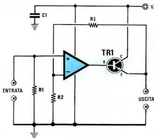
**Fig. 105** Amplificatore di potenza per alimentazione SINGOLA con ingresso "non invertente". In questo circuito occorre utilizzare degli operazionali LM.358 - LM.324 - CA.3130. Il guadagno si calcola con i valori delle resistenze R2 ed R3.
