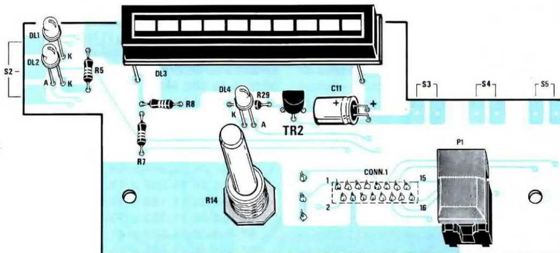
**Fig.10** Schema pratico e foto del circuito stampato LX.1123/B visto dal lato della barra a led. Prima di stagnare la barra e tutti i diodi led dovreste controllare che questi fuoriescano leggermente dal pannello anteriore (leggere la realizzazione pratica).
