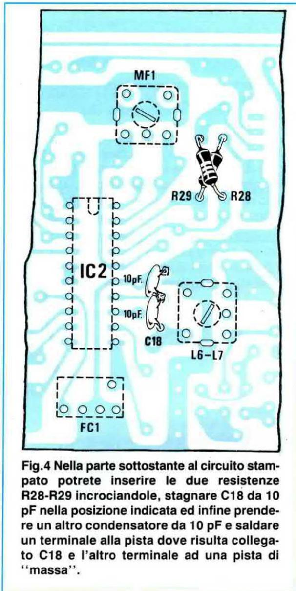
Fig.4 Nella parte sottostante al circuito stampato potrete inserire le due resistenze R28-R29 incrociandole, stagnare C18 da 10 pF nella posizione indicata ed infine prendere un altro condensatore da 10 pF e saldare un terminale alla pista dove risulta collegato C18 e l'altro terminale ad una pista di "massa".
