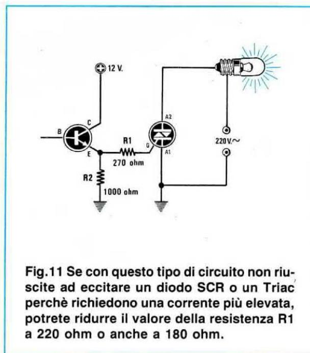
**Fig.11** Se con questo tipo di circuito non riuscite ad eccitare un diodo SCR o un Triac perchè richiedono una corrente più elevata, potrete ridurre il valore della resistenza R1 a 220 ohm o anche a 180 ohm.
