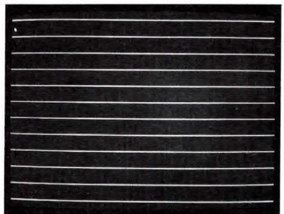
Fig.6 Le linee orizzontali in bianco/nero servono per controllare se la linearità e la focalizzazione in senso orizzontale sono perfette. Le righe devono apparire nitide.
