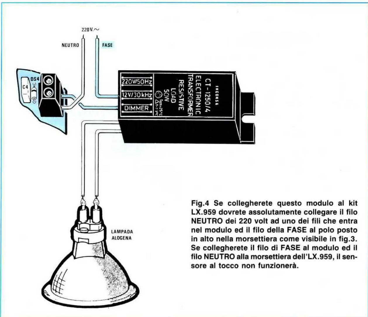
**Fig.4** Se collegherete questo modulo al kit LX.959 dovrete assolutamente collegare il filo **NEUTRO** dei 220 volt ad uno dei fili che entra nel modulo ed il filo della **FASE** al polo posto in alto nella morsettiera come visibile in fig.3. Se collegherete il filo di **FASE** al modulo ed il filo **NEUTRO** alla morsettiera dell'LX.959, il sensore al tocco non funzionerà.
