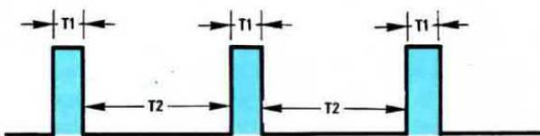
Fig. 19 Se il tempo T1 delle semionde positive è "minore" rispetto al tempo delle semionde negative T2, il sensore indicherà una potenza "minore" rispetto a quella che potete leggere con un duty-cycle del 50%.
