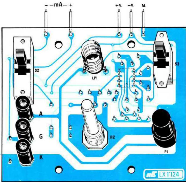
Fig.5 Schema pratico del circuito visto dal lato frontale. In basso la foto con i componenti già inseriti. Il pulsante P1 va applicato rivolgendo la parte smussata verso destra.
