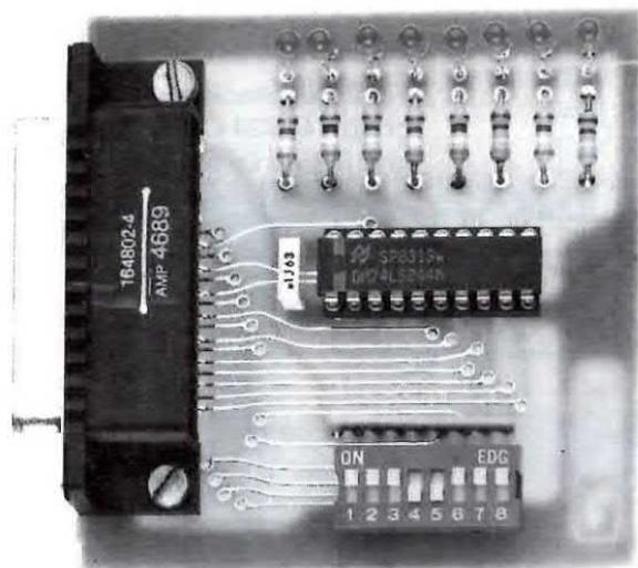
tegrato e per far accendere i diodi led verranno prelevate direttamente dall'interfaccia seriale/parallelo **LX.1127** tramite il connettore d'ingresso.
