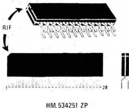
**Fig.35** Le due Video Ram IC1-IC2 hanno, a differenza degli altri integrati, due file di 14 piedini poste da un solo lato del corpo. Per innestarle vi consigliamo di individuare il lato leggermente "smussato" (vedi scritta riferimento) e di rivolverlo in basso come visibile in fig.27.
