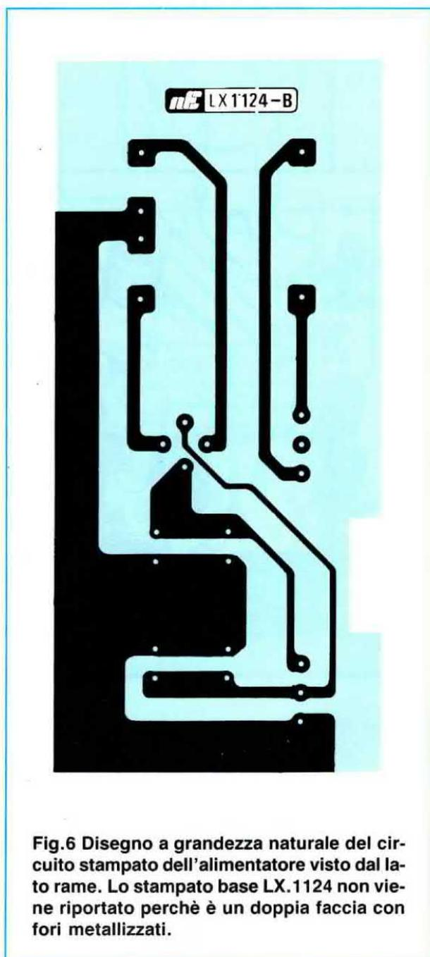
**Fig.6** Disegno a grandezza naturale del circuito stampato dell'alimentatore visto dal lato rame. Lo stampato base LX.1124 non viene riportato perchè è un doppia faccia con fori metallizzati.
