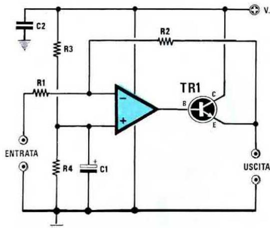
**Fig. 104** Amplificatore di potenza per alimentazione SINGOLA con ingresso "invertente". I valori delle resistenze R1 ed R2 determinano il guadagno.
