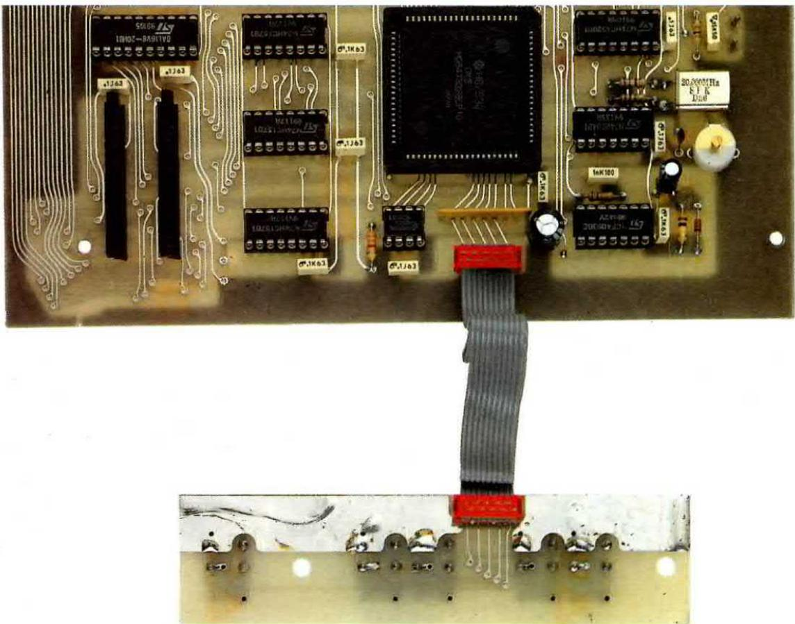
**Fig.32** La piattina dovrà essere inserita nei due stampati LX.1121 e LX.1121/B come visibile in figura. Per evitare di inserire gli zoccoli in senso opposto al richiesto, nei due zoccoli maschi è presente un piccolo "dente" che s'innesterà nel piccolo foro presente su un solo lato dei due circuiti stampati.
