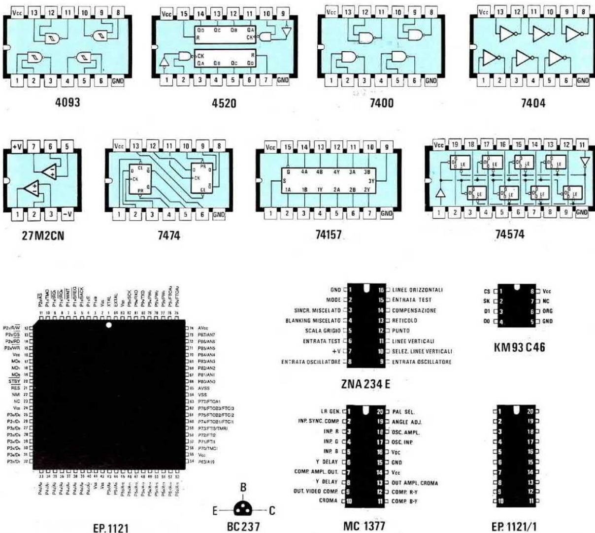
**Fig.34** Connessioni di tutti gli integrati utilizzati in questo progetto viste da sopra e quelle del transistor BC.237 viste da sotto. Per la CPU IC1 abbiamo riportato la sigla EP.1121 perchè nella sua memoria sono memorizzati i tre monoscopi e tutte le altre figure a colori ed in bianco/nero. Per la Gal 16V8, siglata IC7, abbiamo riportato la sigla EP.1121/1 perchè anche questa è stata programmata.
