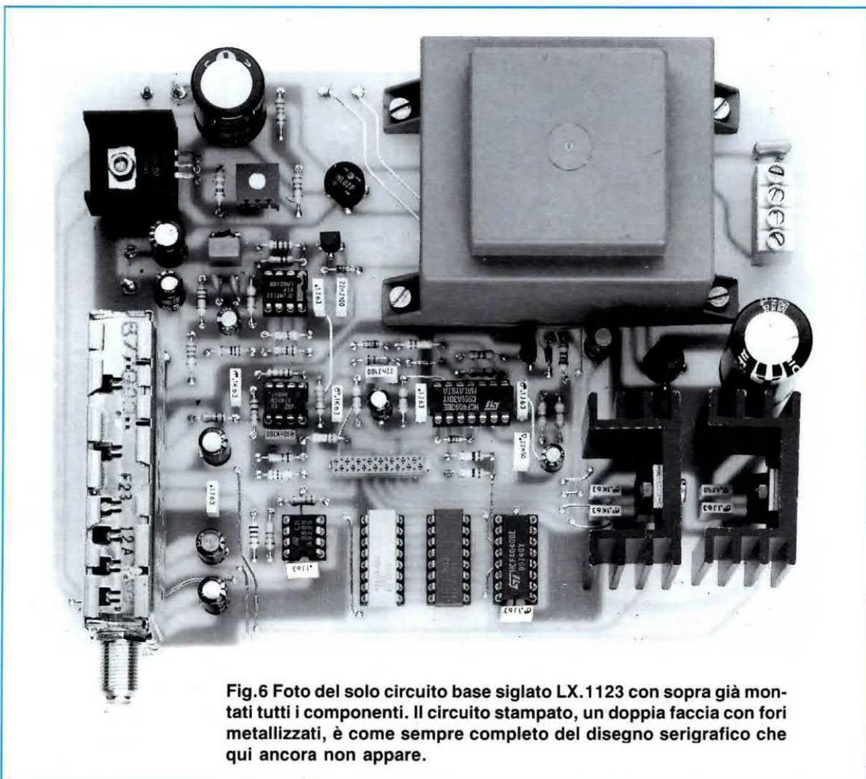
**Fig.6** Foto del solo circuito base siglato **LX.1123** con sopra già montati tutti i componenti. Il circuito stampato, un doppia faccia con fori metallizzati, è come sempre completo del disegno serigrafico che qui ancora non appare.
