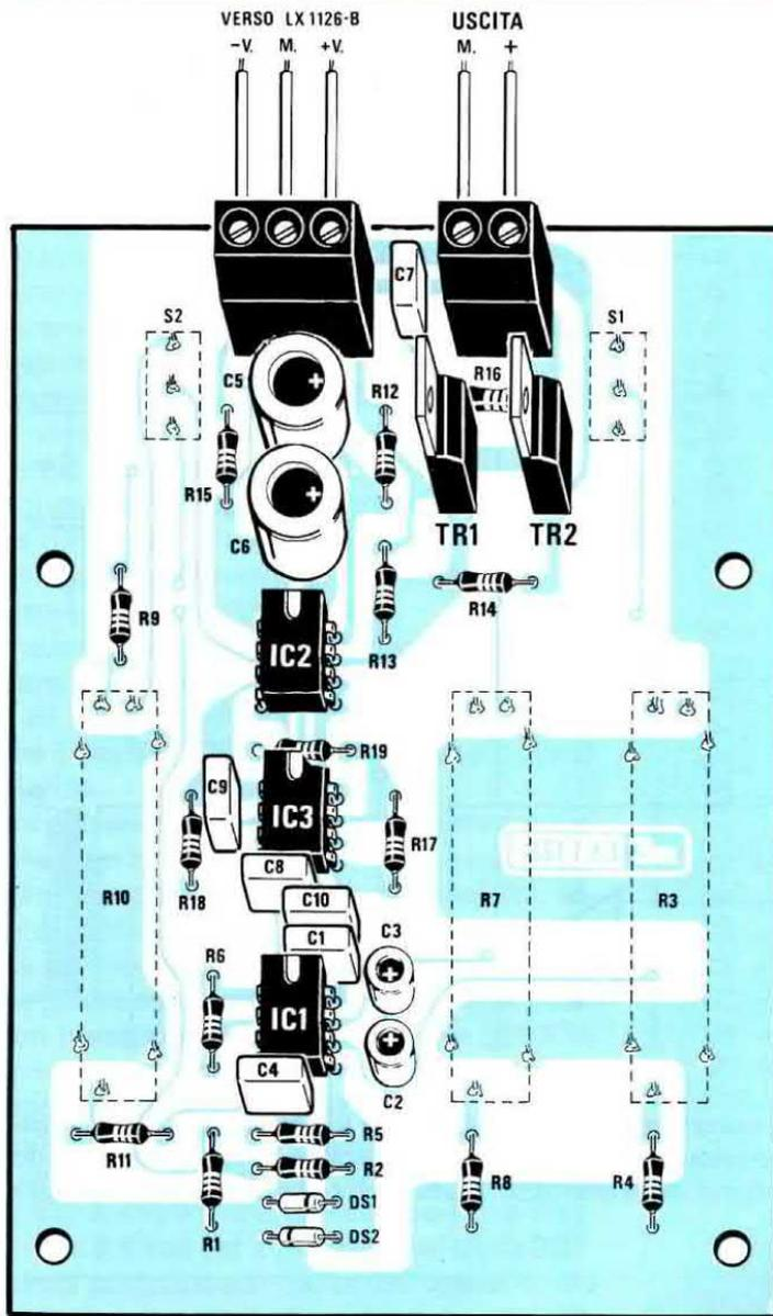
Fig.9 Schema pratico di montaggio dello stampato LX.1126 visto dal lato in cui dovrete montare la maggior parte dei componenti. Sul retro dello stampato monterete i componenti visibili in fig.13.
