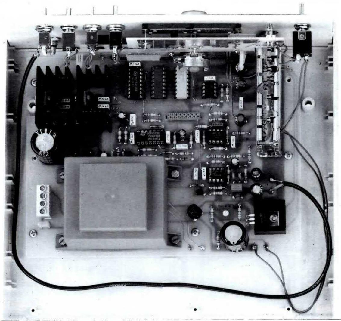
**Fig.5** Foto dello Scanner già inserito all'interno del suo mobile plastico. Questo mobile, come avete già visto nella foto sopra il "titolo" all'inizio dell'articolo, è provvisto di una maniglia per essere trasportato più facilmente.
