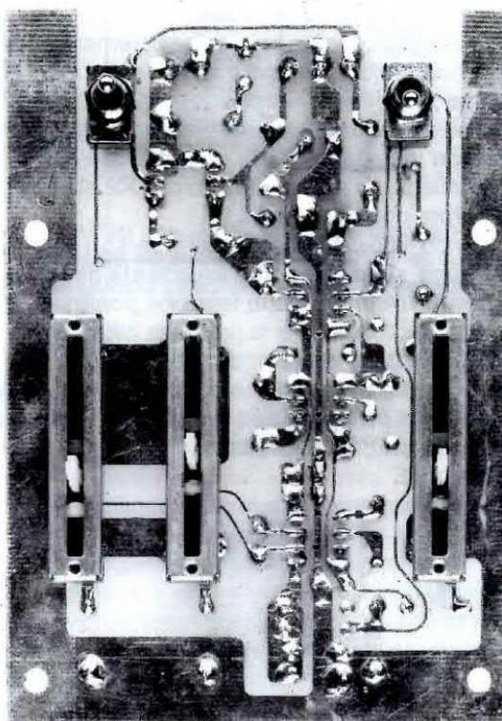
Fig.7 Dal lato opposto di questo stampato fissarete i tre potenziometri a slitta ed i due deviatori a levetta che vi serviranno per passare da "automatico" a "manuale". **IMPORTANTE** = Prima di passare da automatico a manuale o viceversa ponete sempre il deviatore S1 su STOP ed il potenziometro R10 al centro.
