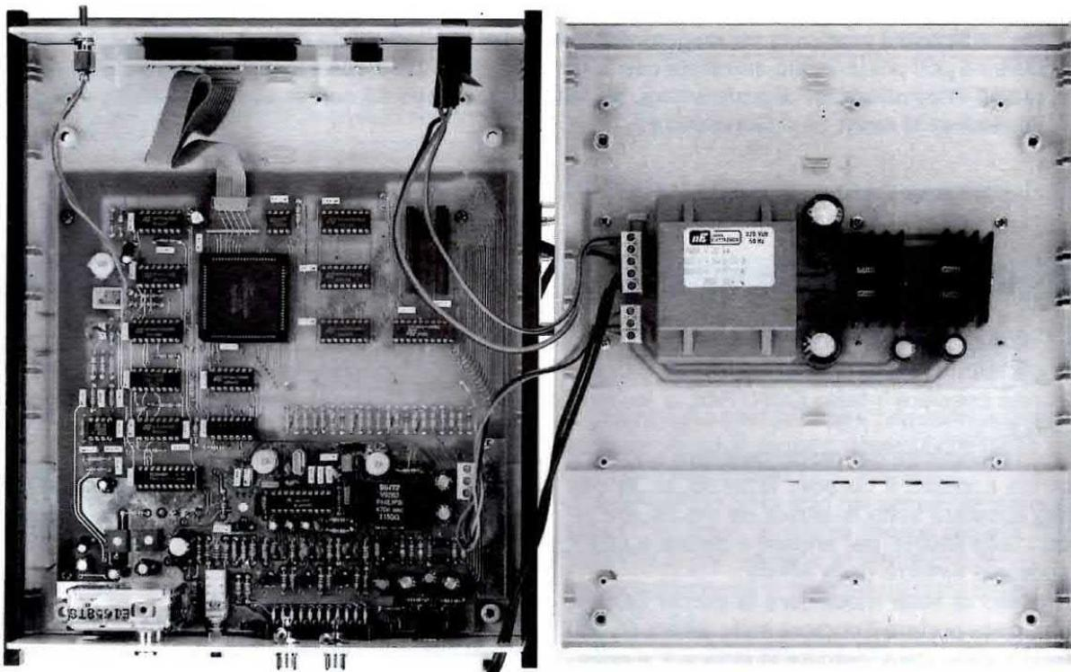
**Fig.37** Sulla parte inferiore della scatola plasticiserete con delle viti autofilettanti il circuito stampato LX.1121, mentre sul coperchio lo stampato LX.1122 dell'alimentatore. Il mobile, come visibile nelle figg.19-20, è completo di una mascherina anteriore e di una posteriore già forate e con tutte le scritte serigrafate.
