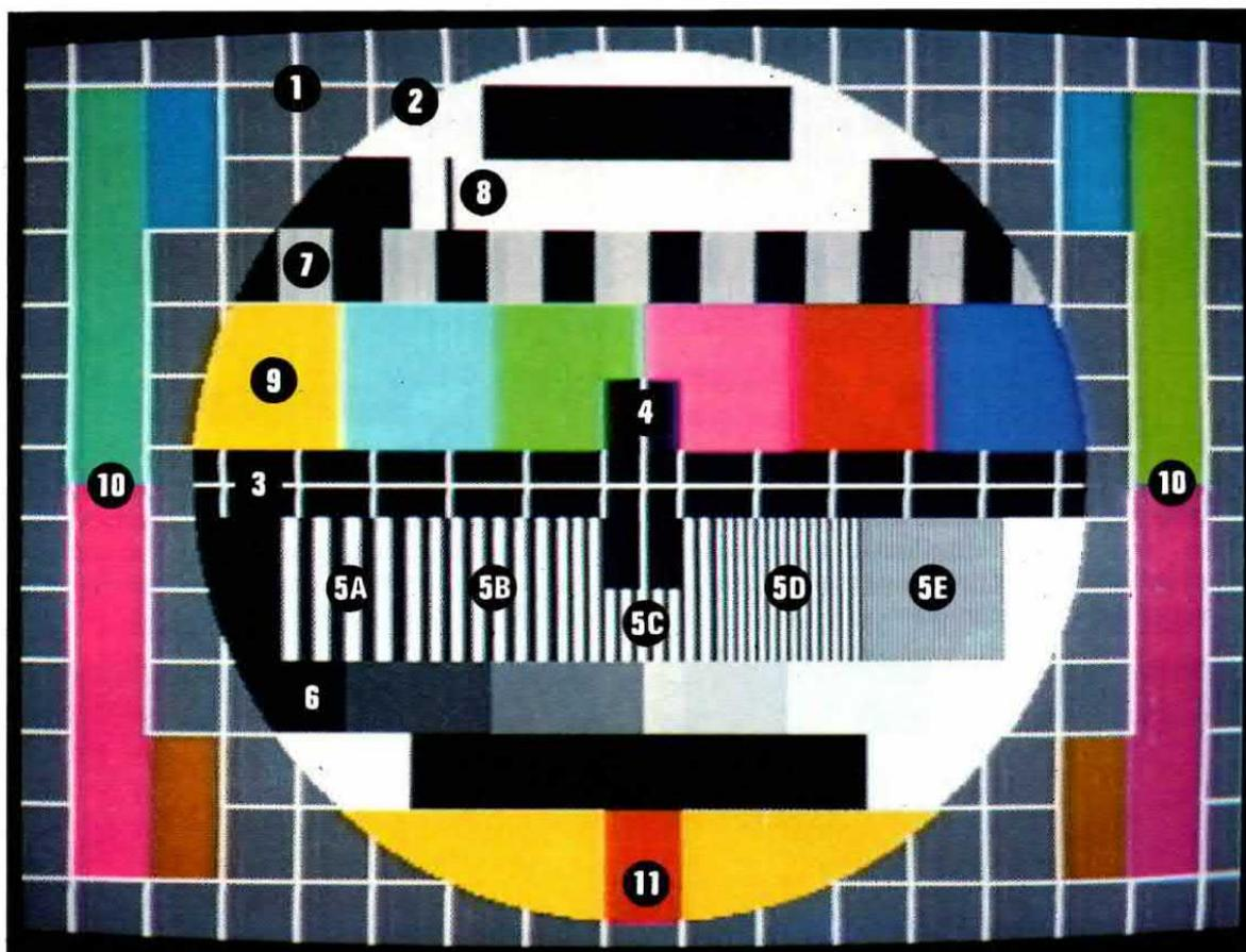
**Fig.38** L'immagine di un qualsiasi monoscopio non viene trasmessa per farvi ammirare una bella figura geometrica piena di colore, ma per fornire una serie d'informazioni utili per controllare se tutti gli stadi presenti in un televisore sono tarati e funzionano in modo corretto (leggi note informative dei settori numerati).
