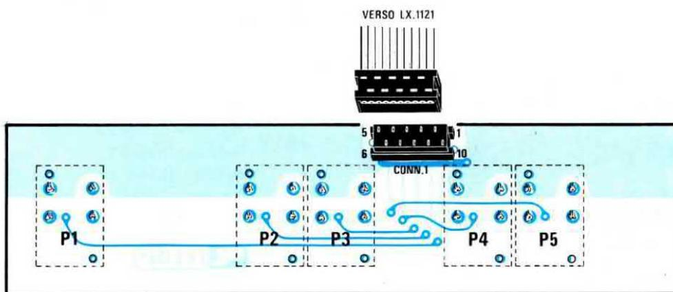
Fig.28 Il circuito stampato LX.1121/B visto dal lato in cui dovrete inserire il connettore CONN.1. La piattina che troverete nel kit è già provvista alle due estremità dei connettori maschi da inserire in questo connettore ed in quello presente nella scheda LX.1121 (vedi in basso a sinistra).
