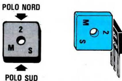
**Fig.14** Nel kit troverete un piccolo magnete quadrato da 190 Gauss con il polo Nord rivolto verso il numero 2 ed il Sud verso M-S. Per tarare il sensore dovreste appoggiare il lato Nord sul lato del sensore dove appare la scritta UGN.
