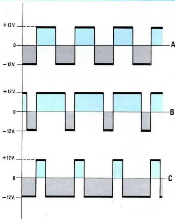
**Fig.1/A** Collegando sulle rotaie una tensione ad onda quadra con un duty-cycle del **50%** la locomotiva rimarrà ferma, ma tutte le lampadine inserite nelle carrozze si accenderanno regolarmente.
