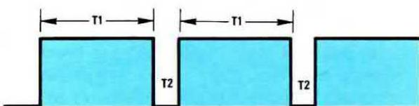
Fig. 18 Se il tempo T1 delle semionde positive è "maggiore" rispetto al tempo delle semionde negative T2, il sensore indicherà una potenza "maggiore" rispetto a quella che leggerebbe con un duty-cycle del 50%.
