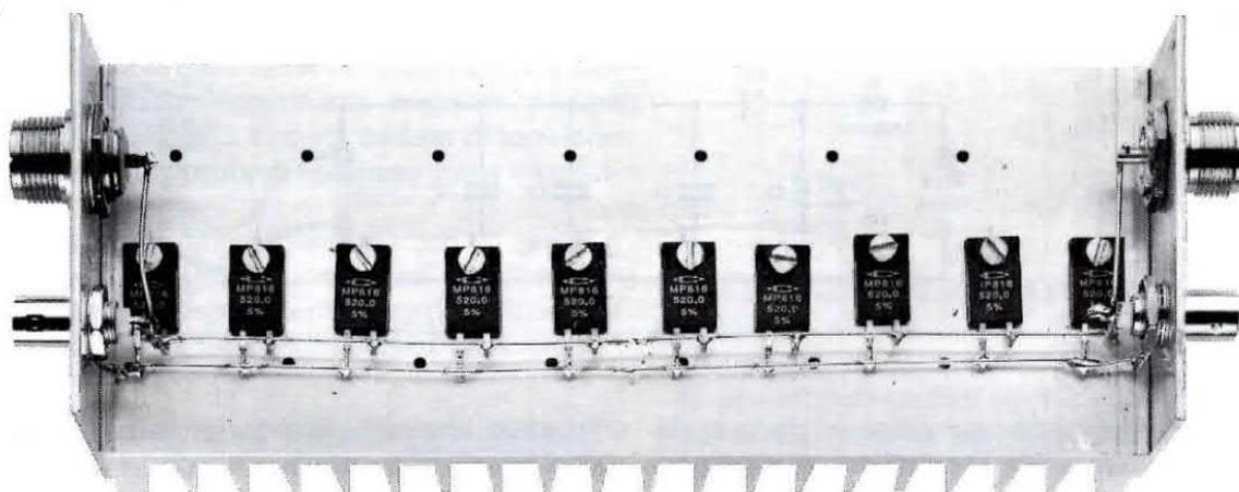
**Fig.4** Come visibile in fig.3, dovete ripiegare a L un piedino di ogni singola resistenza, poi con due fili di rame collegherete in parallelo tutti i piedini. Ai due lati dell'aletta fiserete i due ritagli di alluminio già forati per ricevere i due bocchettoni BNC e PL. Se vicino all'aletta metterete una ventola, la temperatura rimarrà sui 35-40 gradi.
