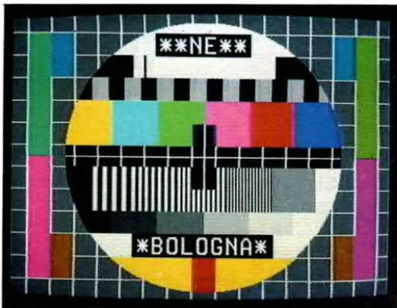
Fig.1 Figura del primo monoscopio che apparirà sullo schermo del televisore. Le scritte all'interno delle fasce nere possono essere sostituite con facilità.
