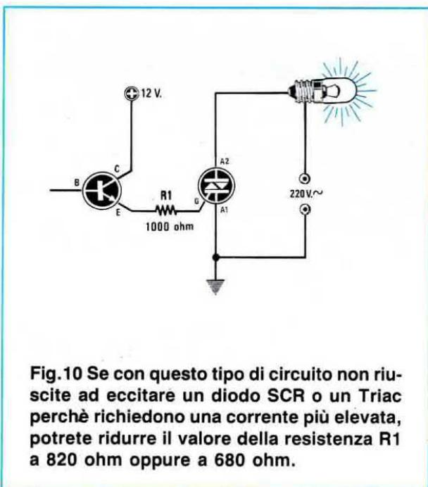
**Fig.10** Se con questo tipo di circuito non riuscite ad eccitare un diodo SCR o un Triac perchè richiedono una corrente più elevata, potrete ridurre il valore della resistenza R1 a 820 ohm oppure a 680 ohm.
