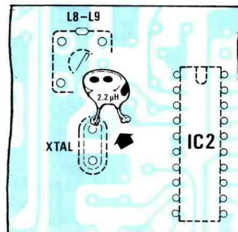
Fig.6 Se il vostro quarzo ha difficoltà ad oscillare, tranciate con una lama la pista del circuito stampato ed applicate tra il terminale del quarzo e la pista che si collegherà ad R14-R15 ed al piedino 17 dell'SL.6652, una piccola impedenza da 2,2 microHenry.
