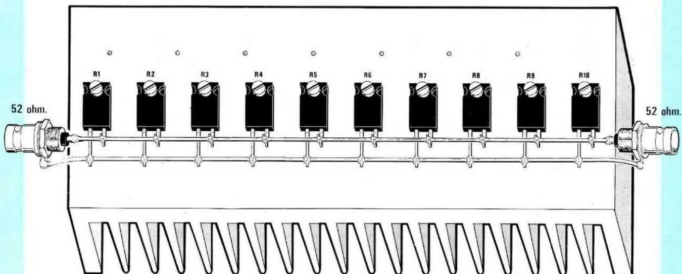
**Fig.3** Tutte le resistenze verranno fissate su un'aletta di elevate dimensioni per essere raffreddate. Come riportato nella Tabella N.1, più aumenta la temperatura minore sarà la potenza RF che la sonda potrà dissipare. Non preoccupatevi se l'aletta raggiunge una temperatura di 40-50 gradi, perchè è una normale temperatura di lavoro.
