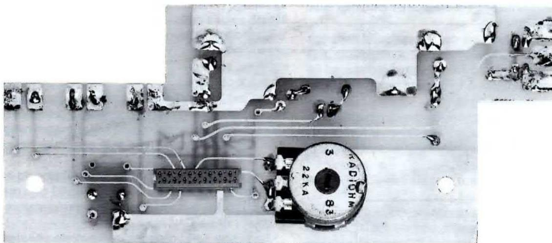
**Fig.9** Foto dello stampato LX.1123/B vista dal lato del potenziometro. I tre terminali del potenziometro andranno collegati al circuito stampato con corti spezzoni di filo di rame nudo. Gli stampati fotografati per essere pubblicati sulla rivista mancano della vernice protettiva, perchè questa coprendo tutte le piste in rame le renderebbe meno visibili.
