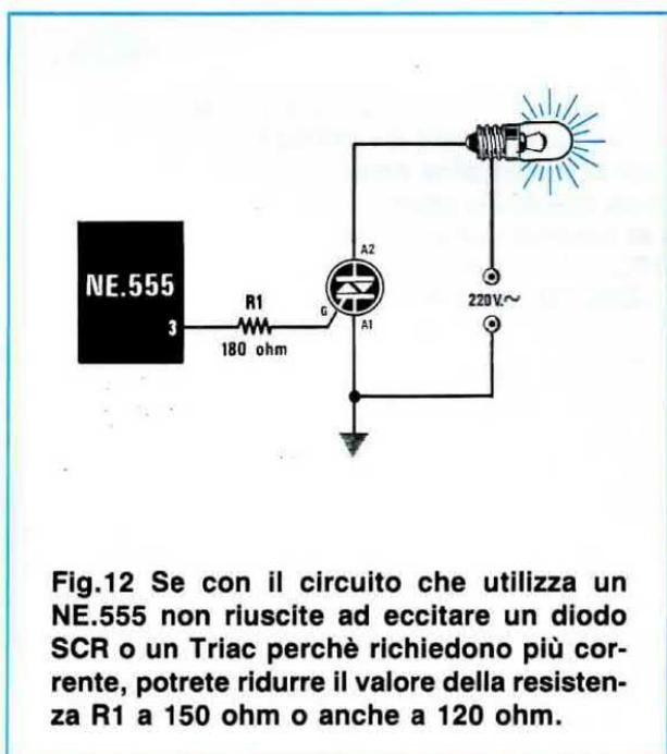
**Fig.12** Se con il circuito che utilizza un **NE.555** non riuscite ad eccitare un diodo **SCR** o un **Triac** perchè richiedono più corrente, potrete ridurre il valore della resistenza **R1** a **150 ohm** o anche a **120 ohm**.
