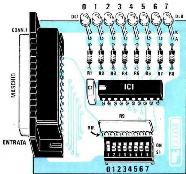
Fig.3 Schema pratico di montaggio della scheda LX.1128. Quando monterete la rete resistiva R1 controllate che il "punto" di riferimento stampigliato sul suo corpo risulti rivolto verso la presa seriale. Inserite in modo corretto anche il dipswitch S1 perchè, in caso contrario, spostando le leve verso l'alto anzichè chiudere i suoi contatti li aprite.
