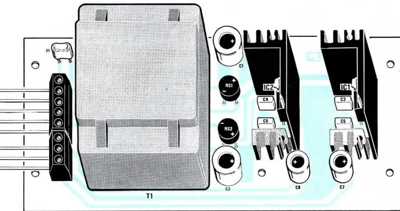
Fig.36 Schema pratico di montaggio dello stadio di alimentazione LX.1122. Nella morsettieria a 5 poli posta in alto entreranno con la tensione della 220 e con i fili 1-2-3 che preleverete dall'interruttore S1 di accensione. Se invertirete questi fili non si accenderanno nè la lampadina al neon nè il Generatore.
