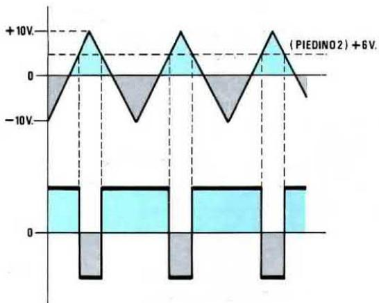
Fig.4 Se sposteremo il cursore del potenziometro in modo che sul piedino "non invertente" giunga una tensione "positiva" rispetto alla massa, sul piedino d'uscita dell'integrato comparatore si avrà un'onda quadra le cui semionde positive risulteranno molto più "larghe" delle semionde negative.
