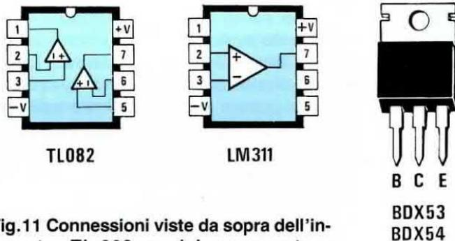
Fig.11 Connessioni viste da sopra dell'integrato TL.082 e del comparatore LM.311. Le connessioni dei due transistor di potenza sono viste frontalmente. Fate attenzione e non confondere i due transistor perchè uno è un NPN e l'altro un PNP.
