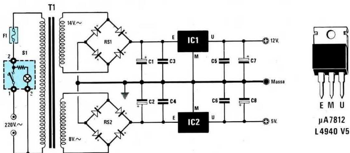
**Fig.25** Schema elettrico dello stadio di alimentazione che monterete sul circuito stampato LX.1122. L'interruttore di accensione S1 contiene al suo interno una piccola lampadina al neon.
