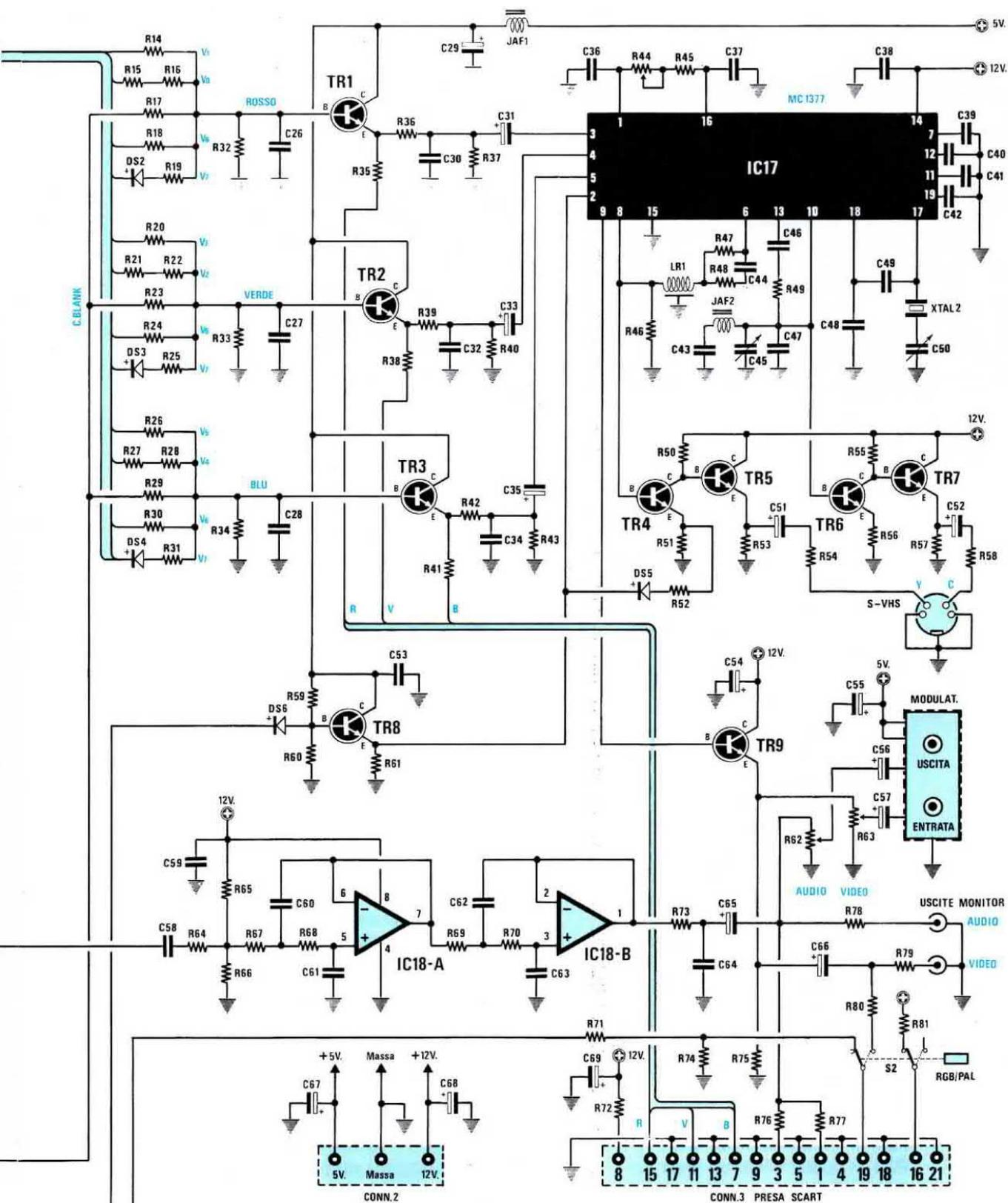
Fig.22 Schema elettrico del Generatore di Monoscopi ad alta definizione escluso il solo stadio di alimentazione visibile in fig.25. La lista componenti è riportata nelle pagine seguenti. Con il circuito stampato già forato e serigrafato questo montaggio non presenta alcuna difficoltà.
