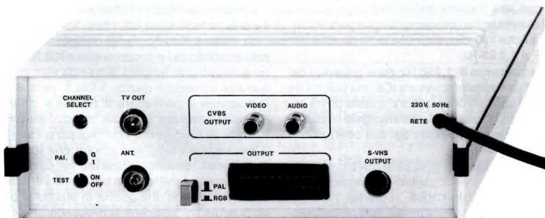
Fig.20 Sul pannello posteriore del mobile sono presenti tutte le uscite per poter collegare il Generatore di Monoscopi a qualsiasi televisore, cioè le prese SCART, CVBS (RCA), S-VHS ed anche una presa in radiofrequenza sintonizzata sul canale UHF 36 (vedi uscita TV-OUT). Il pulsante posto vicino alla presa SCART serve per collegarsi nello standard PAL o RGB.
