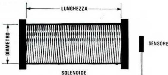
**Fig.15** Avvicinandolo ad un solenoide percorso da una tensione "continua", il sensore misurerà la potenza magnetica che viene erogata. Se la tensione che eccita il solenoide è pulsante, questo misurerà minore potenza (vedi figg.17-18-19).
