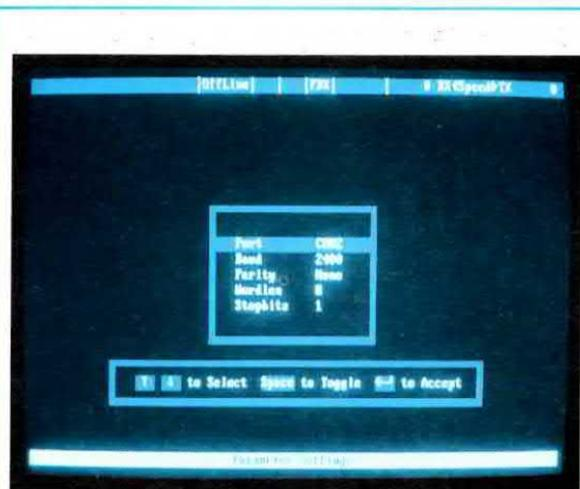
Fig.4 La prima operazione da compiere è quella di configurare la porta seriale premendo i tasti ALT P e la barra spaziatrice.
