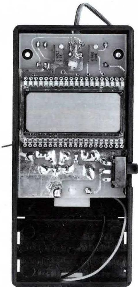
Fig.3 Come si presenta il Gauss/metro montato nel mobile plastico. Sul coperchio di questo mobile è necessario praticare una finestra per poter leggere i numeri visualizzati sul display LCD.
