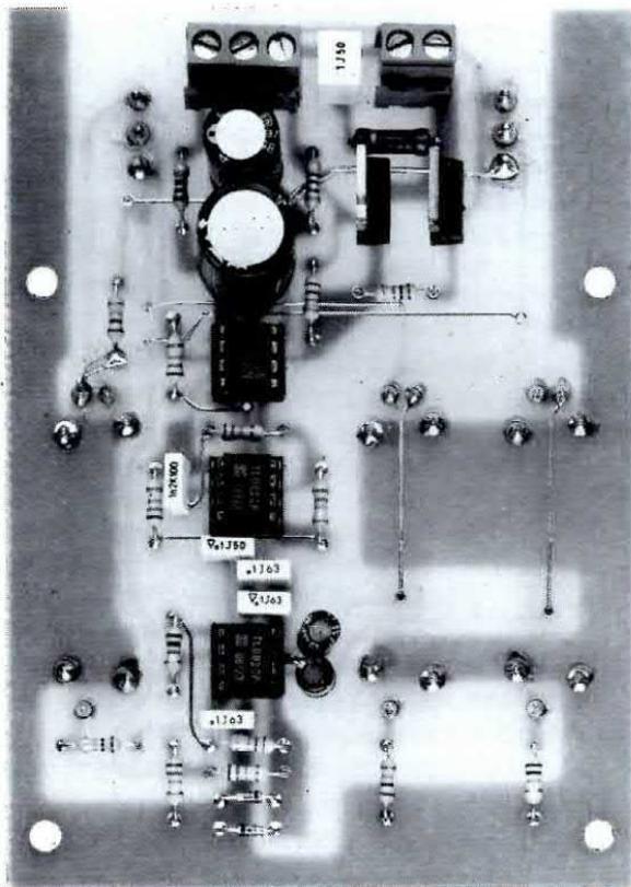
Fig.6 Foto del circuito stampato LX.1126 visto dal lato degli operazionali. Come potete notare, in questo montaggio sono presenti oltre all'integrato "comparatore" anche altri due operazionali che vi serviranno per generare l'onda triangolare a 20.000 Hz e per ottenere l'accelerazione e la decelerazione automatica tramite il deviatore siglato S1.
