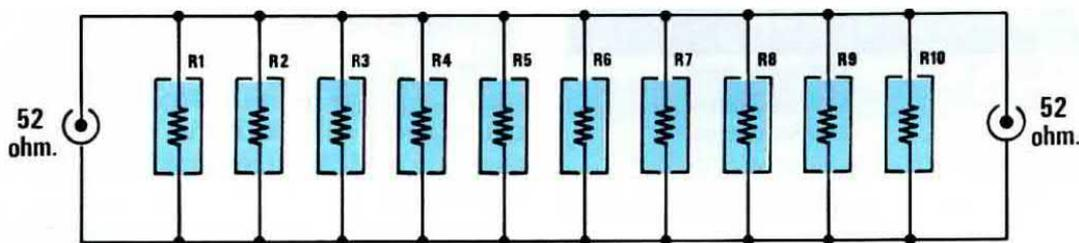
**Fig.2** Collegando in parallelo le 10 resistenze antiinduttive da 520 ohm otterrete un valore di 52 ohm. A causa della tolleranza delle resistenze potrete ottenere dei valori compresi tra 51 e 53 ohm.
