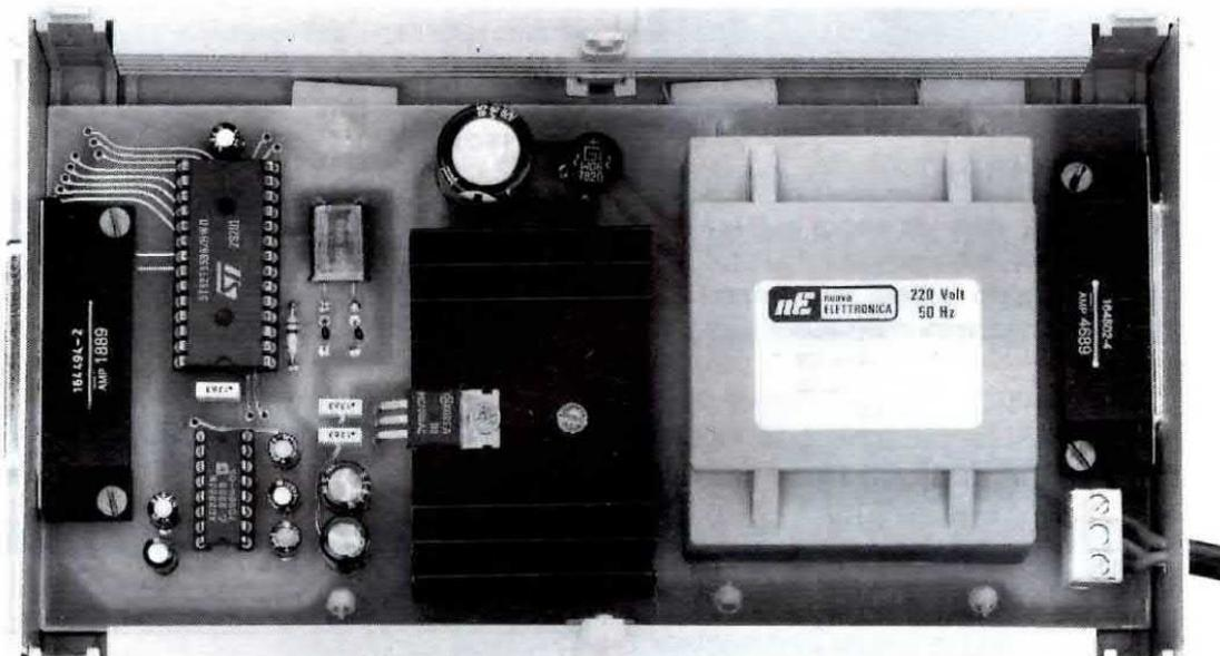
Fig.6 L'interfaccia completa del suo alimentatore verrà fissata all'interno di un appropriato ed elegante mobile plastico. Come accennato nell'articolo, la mascherina frontale e quella posteriore non risultano forate. Nelle interfacce che usiamo in laboratorio abbiamo volutamente tolto queste due mascherine.
