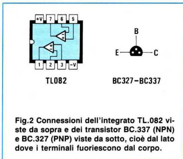
**Fig.2** Connessioni dell'integrato TL.082 viste da sopra e dei transistor BC.337 (NPN) e BC.327 (PNP) viste da sotto, cioè dal lato dove i terminali fuoriescono dal corpo.
