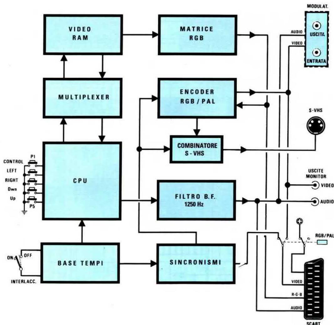
**Fig.21** Schema a blocchi del Generatore di Monoscopi. All'interno della CPU sono memorizzate tutte le immagini che potrete visualizzare pigiando i tasti Up-Dwn. Le immagini verranno trasmesse sulle Video Ram e da qui trasferite sull'Encoder PAL-RGB-S/VHS e sul Modulo RF da dove le potrete prelevare per inviarle al televisore.
