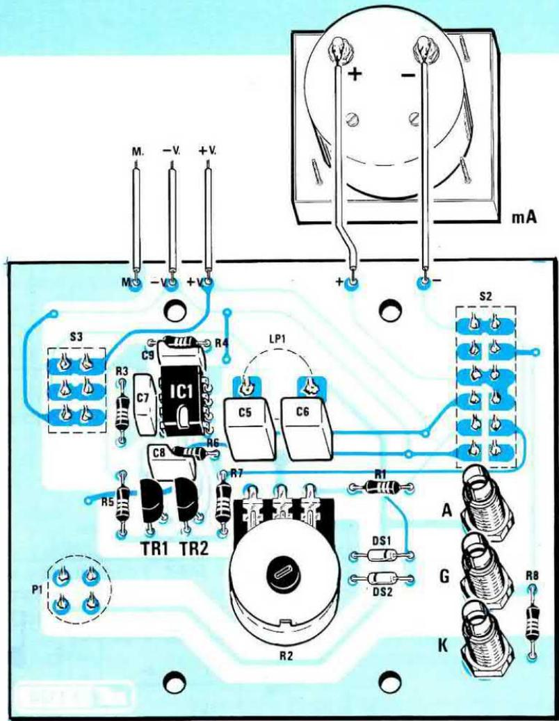
Fig.4 Schema pratico del circuito visto dal lato posteriore. In basso la foto con tutti i componenti già montati. Lo stampato che vi forniremo risulta completo di disegno serigrafico.
