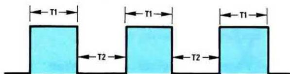
Fig. 17 Se un solenoide viene eccitato da un'onda quadra con un duty-cycle del 50%, il sensore indicherà una potenza in Gauss dimezzata rispetto a quella che fornirebbe se eccitato da una tensione continua.
