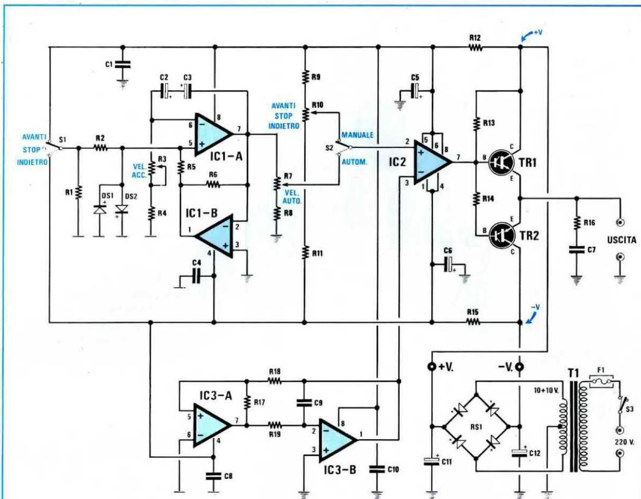
**Fig.8** Schema elettrico dell'alimentatore per ferromodellisti che vi permetterà di far avanzare, retrocedere, accelerare e decelerare una locomotiva ed anche di fermarla tenendo sempre accese le lampadine all'interno delle carrozze. Questo circuito è in grado di fornire una corrente di 1-1,2 Amper.
