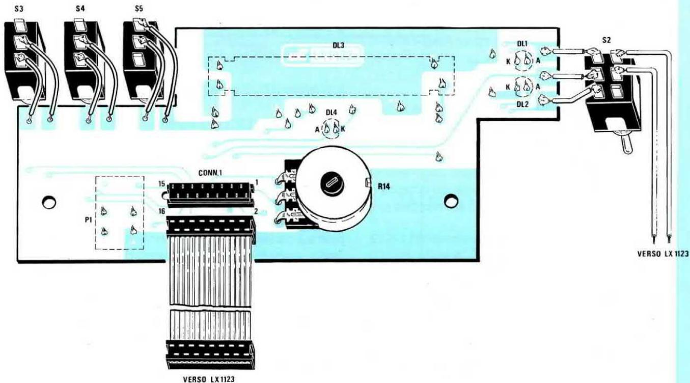
**Fig.8** Schema pratico del circuito di visualizzazione LX.1123/B visto dal lato del potenziometro. Collegando i fili dal circuito stampato ai terminali dei deviatori S3-S4-S5-S2, dovrete cercare di non invertirli, altrimenti otterrete un'indicazione opposta a quella indicata sulla mascherina serigrafata.
