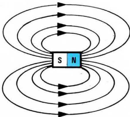
**Fig.11** Ogni magnete genera un campo magnetico che partendo da un polo raggiunge il polo opposto. L'intensità del campo dipende dalla potenza in Gauss del magnete.
