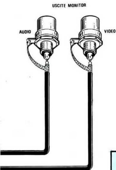
Fig.27 Nella pagina di sinistra lo schema pratico del Generatore di Monoscopi. Il montaggio non presenta alcuna difficoltà e questo lo possiamo affermare dopo aver fatto montare diversi esemplari ad allievi di Istituti di elettronica. Gli errori più comuni che qualcuno ha commesso sono stati quelli di non rivolgere il PUNTO di IC6 e della rete resistiva R1 verso destra e di non aver posto il lato "smusato" delle memorie IC1-IC2 verso il basso (vedi fig.35).
