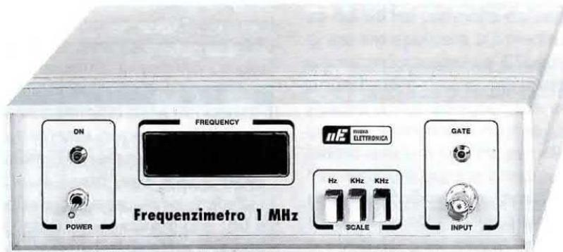
Questo circuito è stato progettato per accontentare tutti coloro che ci hanno chiesto un semplice e sensibile frequenzimetro digitale da usare per i soli segnali di BF. Il circuito dispone di tre portate: la prima ha un fondo scala di 9.999 Hz, la seconda ha un fondo scala di 99,99 KHz e la terza ha un fondo scala di 999,9 KHz.
