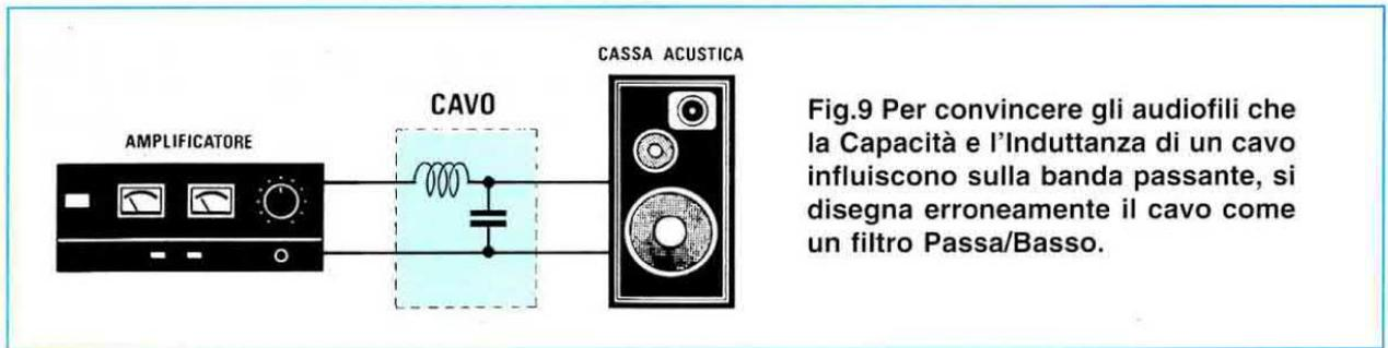
Fig.9 Per convincere gli audiofili che la Capacità e l'Induttanza di un cavo influiscono sulla banda passante, si disegna erroneamente il cavo come un filtro Passa/Basso.
