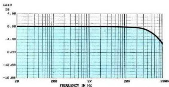
**Fig.14** Un cavo per altoparlanti costruito usando del normale filo da elettricista, come visibile in fig.16, inizierà ad attenuare tutte le frequenze oltre i **60.000 Hz**, quindi con un basso costo avrete realizzato un ottimo cavo per altoparlanti.
