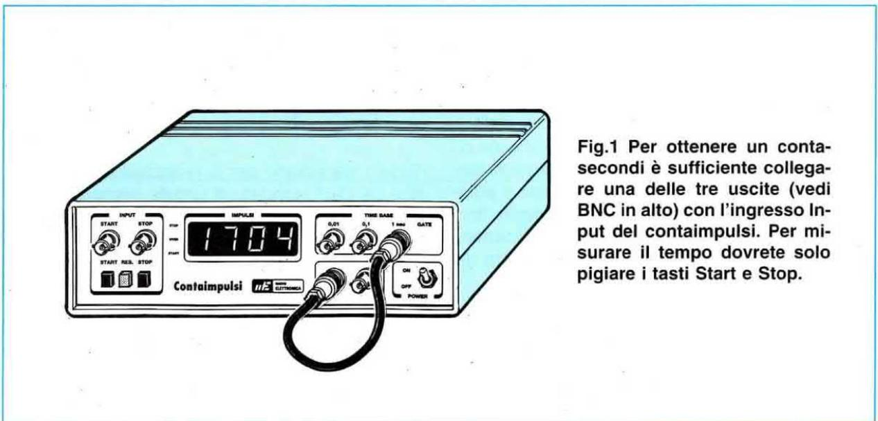
Fig.1 Per ottenere un **contasecondi** è sufficiente collegare una delle tre uscite (vedi BNC in alto) con l'ingresso **Input** del contaimpuls. Per misurare il tempo dovrete solo pigiare i tasti **Start** e **Stop**.
