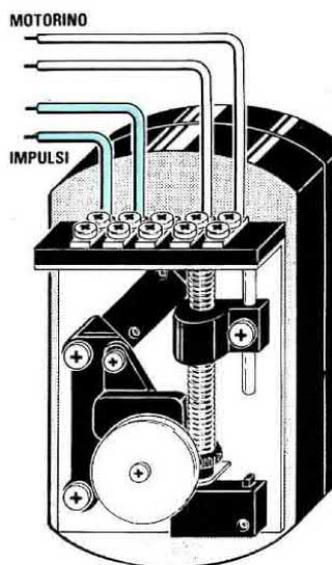
Fig.16 Aprendo il coperchio del motorino a stantuffo troverete al suo interno una morsettiera per poterlo alimentare. Sui morsetti indicati "motorino" dovete applicare una tensione di circa 30-35 volt e sui morsetti indicati "impulsi" preleverete un segnale che andrà applicato sul BOX di controllo (pubblicheremo questo progetto sul prossimo numero). In questi disegni, le connessioni da effettuare sulle diverse morsettiera.
