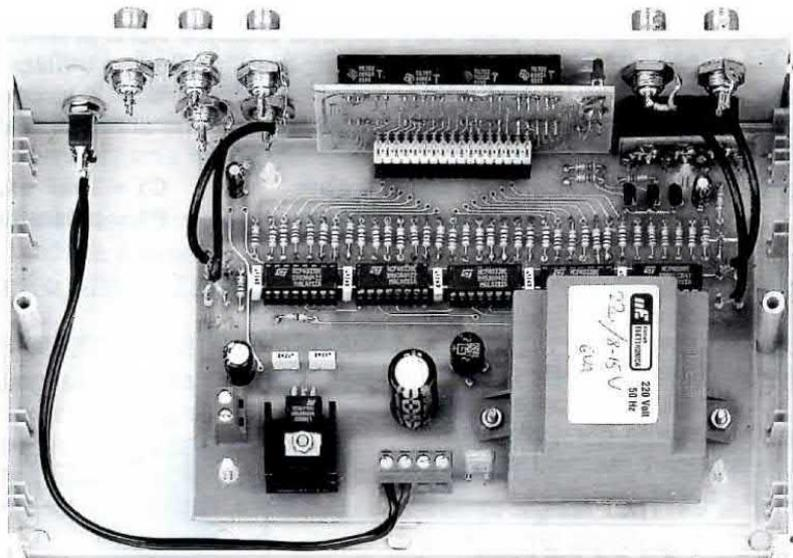
**Fig.6** La scheda base LX.1188, completa della scheda dei display siglata LX1188/B, verrà fissata sul piano del mobile con dei distanziatori plastici autoadesivi. Sui tre bocchettoni BNC fissati in alto a sinistra sul pannello frontale andrà fissato il kit della Base dei Tempi siglato LX.1189.
