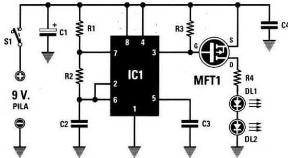
Fig.2 Schema elettrico dello stadio trasmettente. Quando collegherete in serie i fotodiodi all'infrarosso LD.271 dovreste necessariamente rivolgere il terminale più corto K di entrambi (vedi fig.5) verso destra, come appare ben visibile nello schema pratico di fig.3.
