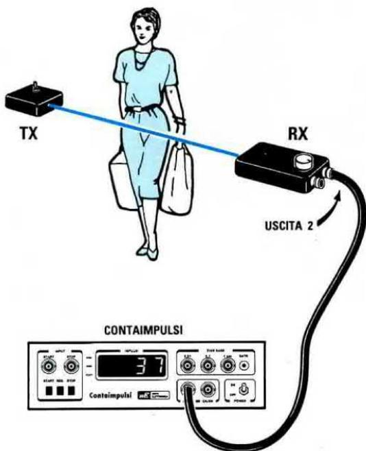
Fig.6 Applicando un trasmettitore ed un ricevitore sulla porta d'ingresso o in un passaggio obbligato avrete realizzato un preciso contapersone. Come visibile in figura, l'uscita del ricevitore andrà applicata sul connettore indicato INPUT del contaimpulsi.
