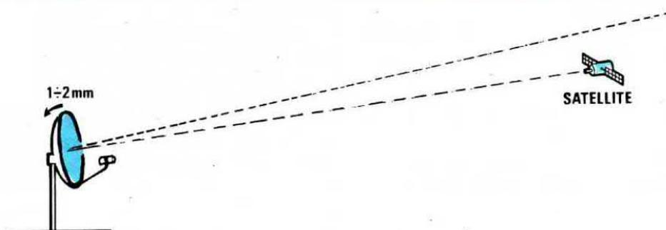
**Fig.1** Poiché il satellite si trova a **36.000 Km** di distanza dalla Terra, per poterlo "centrare" bisogna muovere la parabola sia in orizzontale sia in verticale di pochi millimetri, diversamente non sarà possibile trovarlo.
