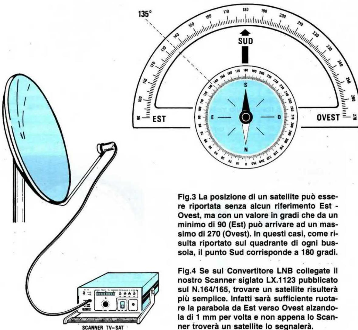
**Fig.3** La posizione di un satellite può essere riportata senza alcun riferimento Est - Ovest, ma con un valore in gradi che da un minimo di 90 (Est) può arrivare ad un massimo di 270 (Ovest). In questi casi, come risulta riportato sul quadrante di ogni bussola, il punto Sud corrisponde a 180 gradi.
