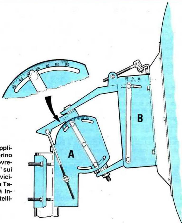
**Fig.11** Se sulla parabola avete applicato un Polarmount ed un motorino a pistone per poterla ruotare, dovrete subito inclinare il "supporto A" sui gradi relativi alla provincia più vicina alla vostra città, riportati nella Tabella N.1. Il "supporto B" andrà inclinato in modo da ricevere il satellite più vicino al punto Sud.
