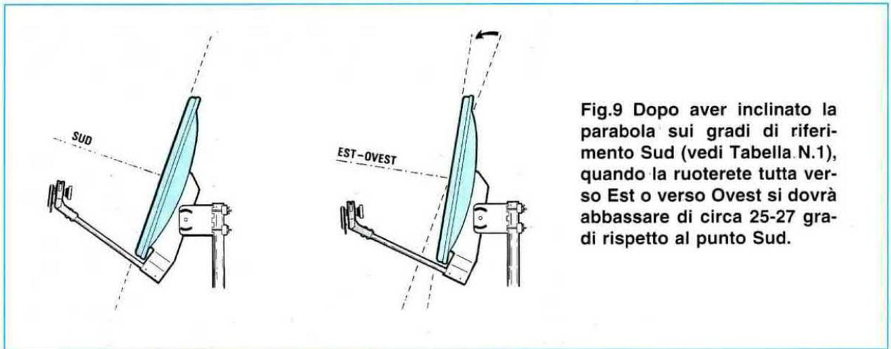
Fig.9 Dopo aver inclinato la parabola sui gradi di riferimento Sud (vedi Tabella N.1), quando la ruoterete tutta verso Est o verso Ovest si dovrà abbassare di circa 25-27 gradi rispetto al punto Sud.
