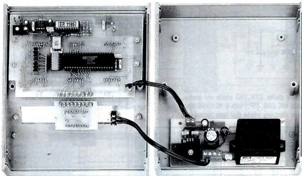
**Fig.4** Sul coperchio del mobile (vedi lato sinistro) fisserete con le torrette in ottone lo stampato LX.1185 e sulla base (vedi lato destro) lo stadio di alimentazione LX.1185/C tenendolo molto vicino al pannello posteriore. Potrete fissare il piccolo altoparlante sul pannello di alluminio frontale o posteriore, o direttamente sul piano base del mobile con una goccia di collante, non dimenticando di forare il mobile per far fuoriuscire il suono.
