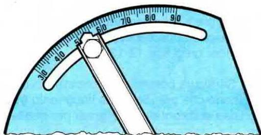
**Fig.12** Dovete inclinare il "supporto A" con i gradi riportati nella colonna TIPO 1 solo se la sua scala risulta graduata per la "massima" elevazione sui 90 gradi e per la "minima" elevazione su 0 gradi.
