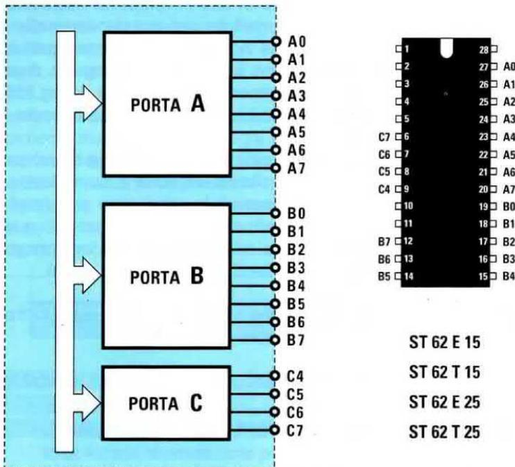
Fig.3 All'interno dei microprocessori ST62 della serie 15-25 sono presenti tre PORTE chiamate A-B-C. Nelle due porte A-B sono presenti otto piedini Ingressi/Uscita siglati da A0 a A7 e da B0 a B7, mentre nella porta C troviamo solo quattro piedini siglati C4-C5-C6-C7.
