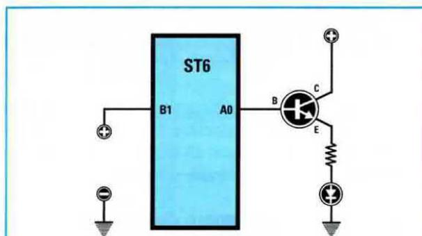
**Fig.9** Per accendere il diodo led applicato sul piedino A0 quando la tensione sul piedino B1 supera i 3 Volt, dovrete scrivere il programma posto a fine pagina. Leggere attentamente la soluzione dell'Esempio N.14.
