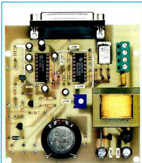
**Fig.7** Foto di come si presenta la scheda **LX.1184** a montaggio ultimato. Per fissare l'altoparlante potrete stagnare sullo stampato due corti spezzoni di filo di rame che ripiegherete ad **L** sul bordo del suo corpo.
