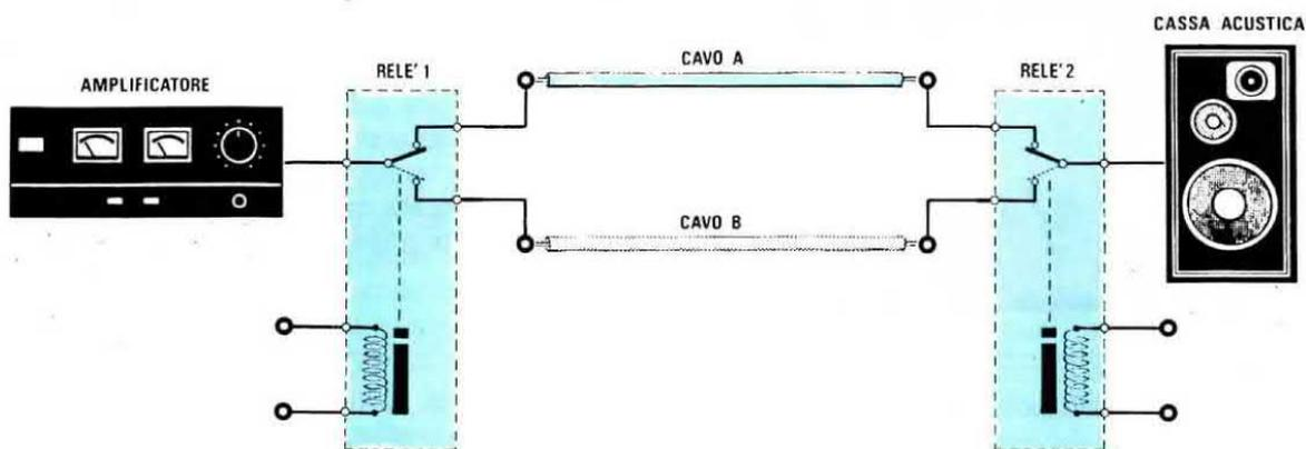
Fig.6 Lo stesso sistema usato per controllare due amplificatori si può utilizzare per verificare la differenza che potrebbe esistere tra un cavo "normale" ed un "supercavo". Un cavo inadeguato può solo "ridurre" leggermente la potenza e non la forma dell'onda.
