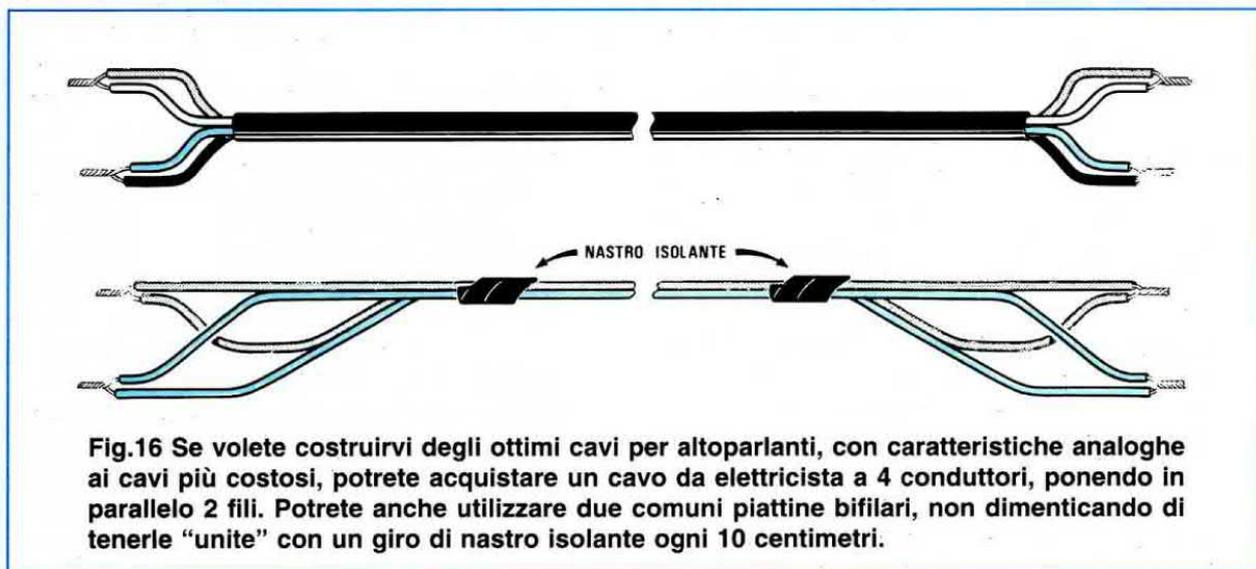
**Fig.16** Se volete costruirvi degli ottimi cavi per altoparlanti, con caratteristiche analoghe ai cavi più costosi, potrete acquistare un cavo da elettricista a 4 conduttori, ponendo in parallelo 2 fili. Potrete anche utilizzare due comuni piattine bifilari, non dimenticando di tenerle "unite" con un giro di nastro isolante ogni 10 centimetri.
