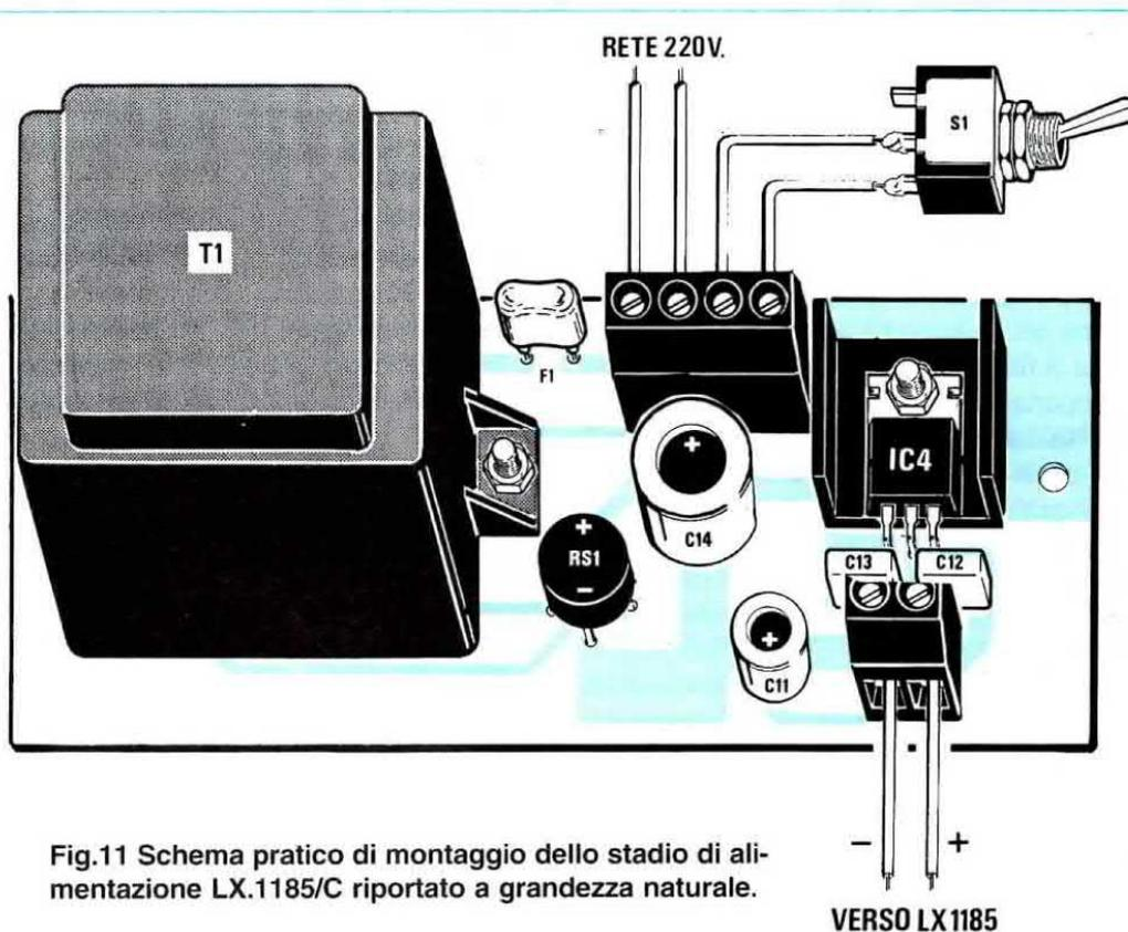
Fig.11 Schema pratico di montaggio dello stadio di alimentazione LX.1185/C riportato a grandezza naturale.
