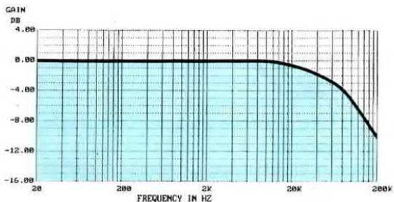
**Fig.15** Il più economico filo bifilare da elettricista, con un diametro rame inferiore al richiesto, inizierà ad attenuare tutte le frequenze oltre i **18.000 Hz**, che, essendo dei **super-acuti**, non sono rilevabili ad orecchio da tutte le persone.
