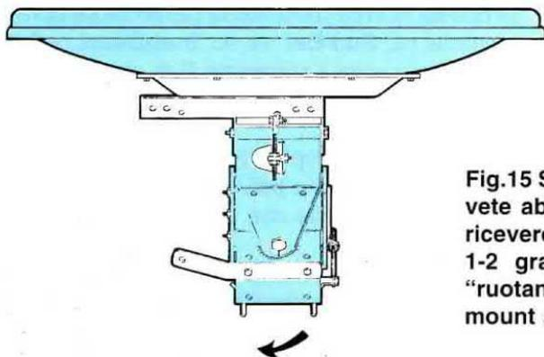
Fig.15 Se per ricevere i satelliti posti ad Est dovete abbassare la parabola di 1-2 gradi e per ricevere quelli posti ad Ovest dovete alzarla di 1-2 gradi, potete correggere questo errore "ruotando" di qualche grado tutto il Polar-mount sul palo di sostegno.
