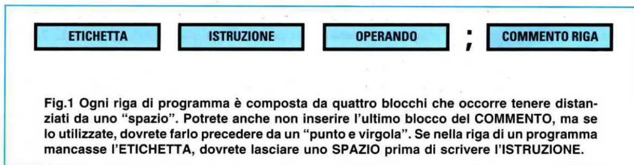
**Fig.1** Ogni riga di programma è composta da quattro blocchi che occorre tenere distanziati da uno "spazio". Potrete anche non inserire l'ultimo blocco del COMMENTO, ma se lo utilizzate, dovrete farlo precedere da un "punto e virgola". Se nella riga di un programma mancasse l'ETICHETTA, dovrete lasciare uno SPAZIO prima di scrivere l'ISTRUZIONE.
