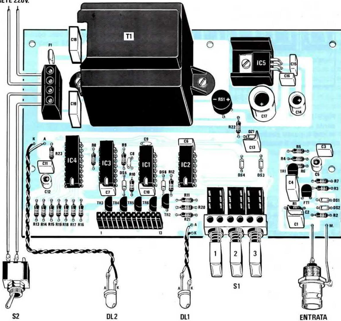
Fig.6 Schema pratico di montaggio del frequenzimetro. Nel piccolo connettore femmina ad 1 fila, posto in basso sotto i transistor, verrà innestata la scheda dei display visibile nelle figg.8-9. Questo circuito non richiede nessuna taratura.
