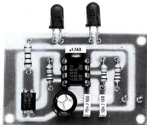
Fig.4 Foto della basetta dello stadio trasmettente a raggi infrarossi con sopra già montati tutti i componenti. Il circuito va alimentato a 9 Volt.
