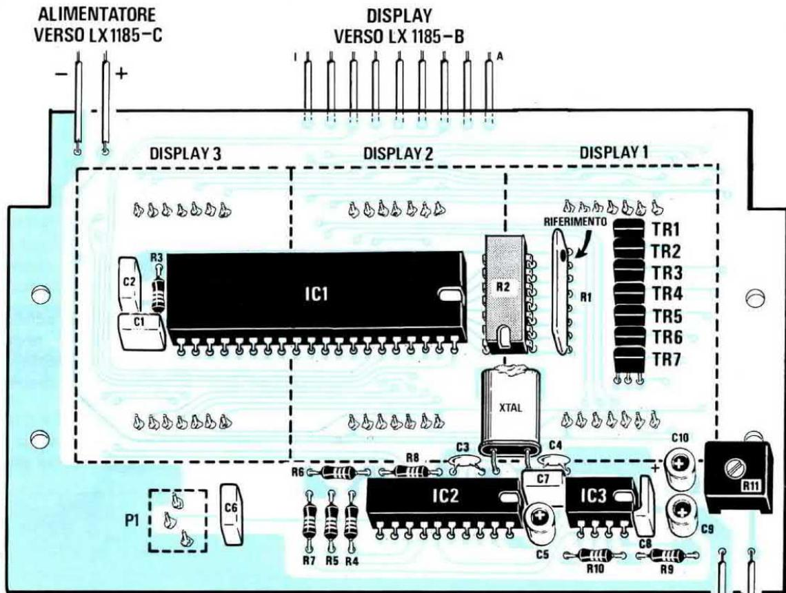
Fig.6 Schema pratico di montaggio della scheda LX.1185 vista da entrambi i lati. Per i display a matrice inserirete nello stampato delle strisce di connettori a 7 terminali. Ricordatevi di rivolgere il terminale della rete resistiva R1 con il "punto" di riferimento verso l'alto.
