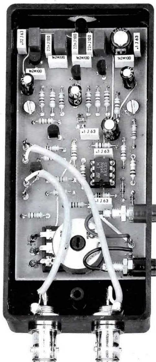
Fig.1 Nella foto in alto a sinistra potete vedere il Trasmettitore siglato LX.1186 già inserito dentro il suo mobile plastico, e nella foto qui sopra il Ricevitore siglato LX.1187 anch'esso già inserito dentro il suo mobile. Si notino in basso i due connettori BNC per le "uscite 1-2" degli impulsi.
