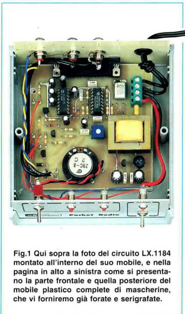
Fig.1 Qui sopra la foto del circuito LX.1184 montato all'interno del suo mobile, e nella pagina in alto a sinistra come si presentano la parte frontale e quella posteriore del mobile plastico complete di mascherine, che vi forniremo già forate e serigrafate.
