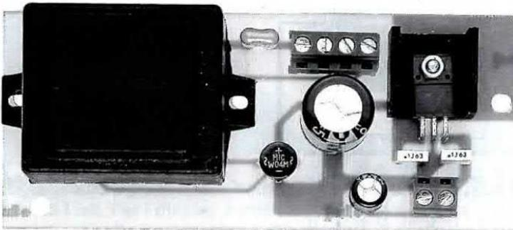
Fig.9 Foto dello stadio di alimentazione LX.1185/C notevolmente ridotta (vedi schema pratico di fig.11).
