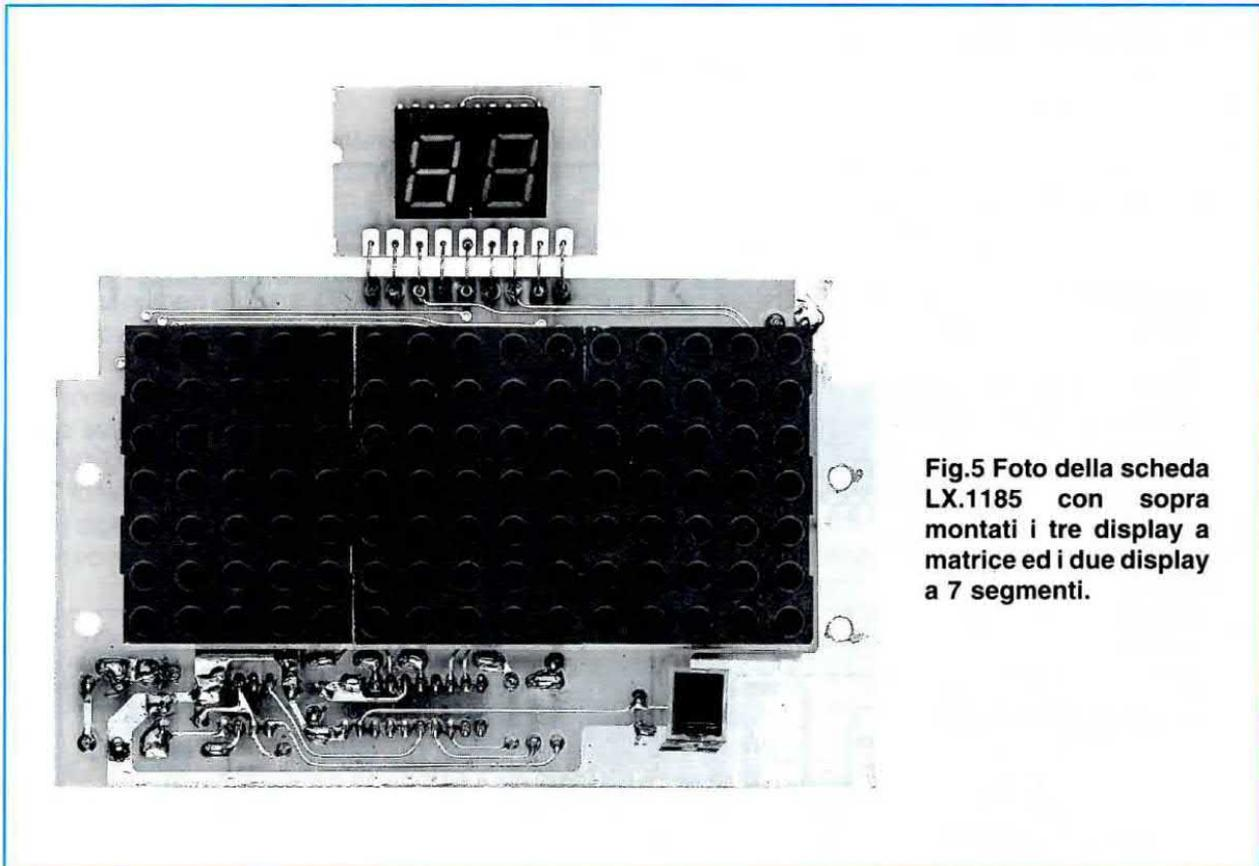
**Fig.5 Foto della scheda LX.1185 con sopra montati i tre display a matrice ed i due display a 7 segmenti.**
