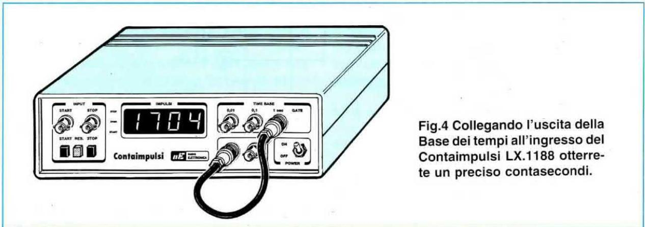
Fig.4 Collegando l'uscita della Base dei tempi all'ingresso del Contaimpuls LX.1188 otterrete un preciso contasecondi.
