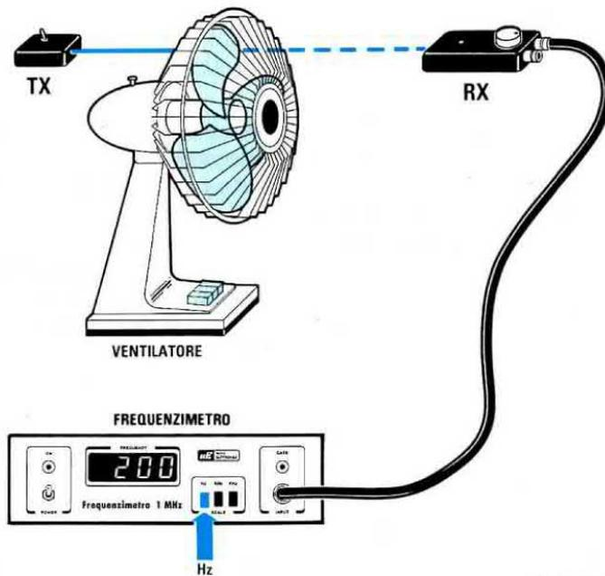
Fig.4 Per conoscere la velocità di rotazione di un ventilatore dovete collocare il trasmettore dietro le sue pale. L'uscita del ricevitore si deve applicare sull'ingresso di un Frequenzimetro digitale. Conoscendo la frequenza potrete calcolare il numero di giri al minuto.
