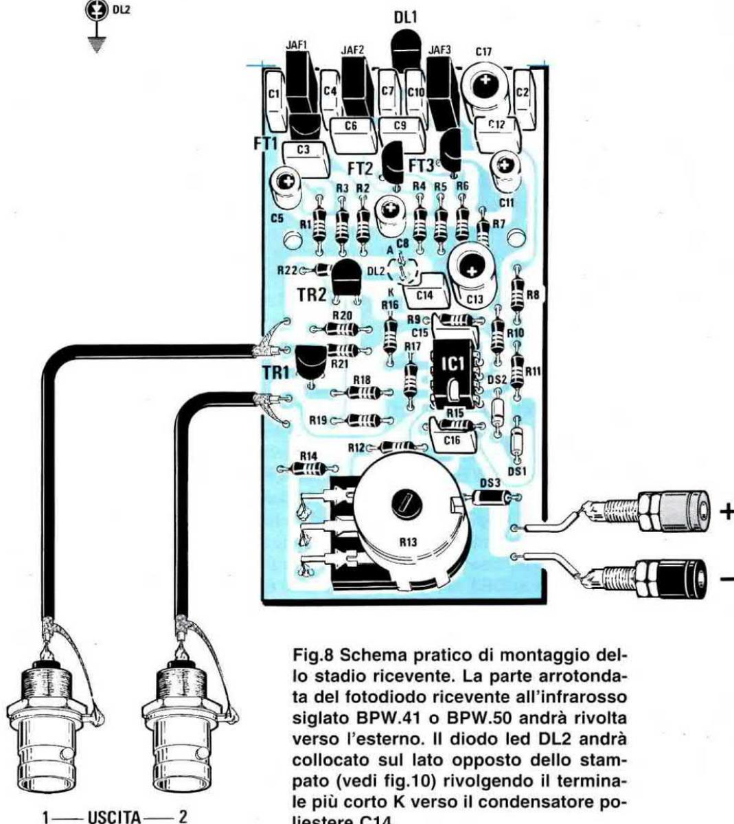
Fig.8 Schema pratico di montaggio dello stadio ricevente. La parte arrotondata del fotodiode ricevente all'infrarosso siglato BPW.41 o BPW.50 andrà rivolta verso l'esterno. Il diodo led DL2 andrà collocato sul lato opposto dello stampato (vedi fig.10) rivolgendolo il terminale più corto K verso il condensatore poliestere C14.
