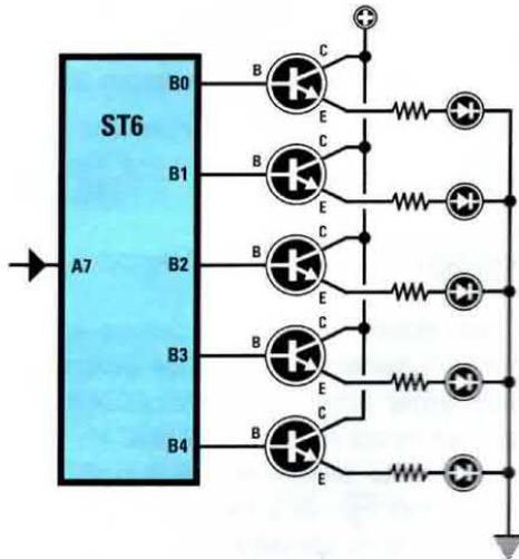
Fig.10 Volendo realizzare un Level-Meter che accenda una fila di 4 led all'aumentare della tensione continua, applicata sul piedino A7 settato come Ingresso, dovrete utilizzare il programma dell'Esempio N.15 riportato sulla pagina in basso a sinistra.
