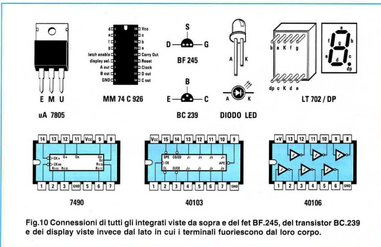
Fig.10 Connessioni di tutti gli integrati viste da sopra e del fet BF.245, del transistor BC.239 e dei display viste invece dal lato in cui i terminali fuoriescono dal loro corpo.
