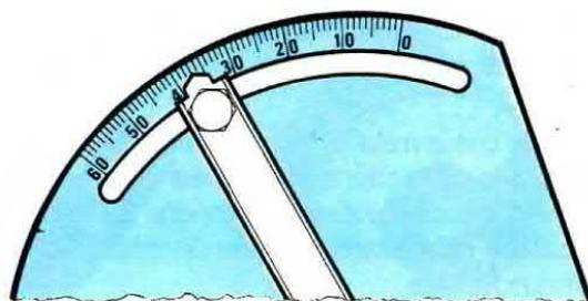
**Fig.13** Se la scala risulta graduata per la "massima" elevazione su 0 gradi e per la "minima" elevazione sui 90 gradi, dovete utilizzare, in corrispondenza della vostra provincia, i dati riportati nella colonna TIPO 2.
