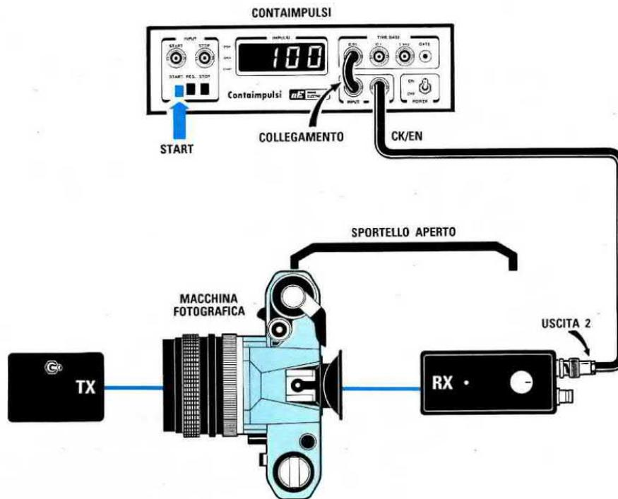
**Fig.8** Per controllare il tempo di apertura e di chiusura del diaframma di una macchina fotografica o di un'altra apparecchiatura dovreste applicare l'uscita del ricevitore sul BNC indicato CK/EN, poi collegare l'uscita della Base Tempi 0,01 secondi sull'ingresso BNC indicato INPUT. Non disponendo di una Base Tempi in grado di fornire un segnale di 0,001 secondi non riuscirete a visualizzare velocità inferiori a 1/100 di secondo.
