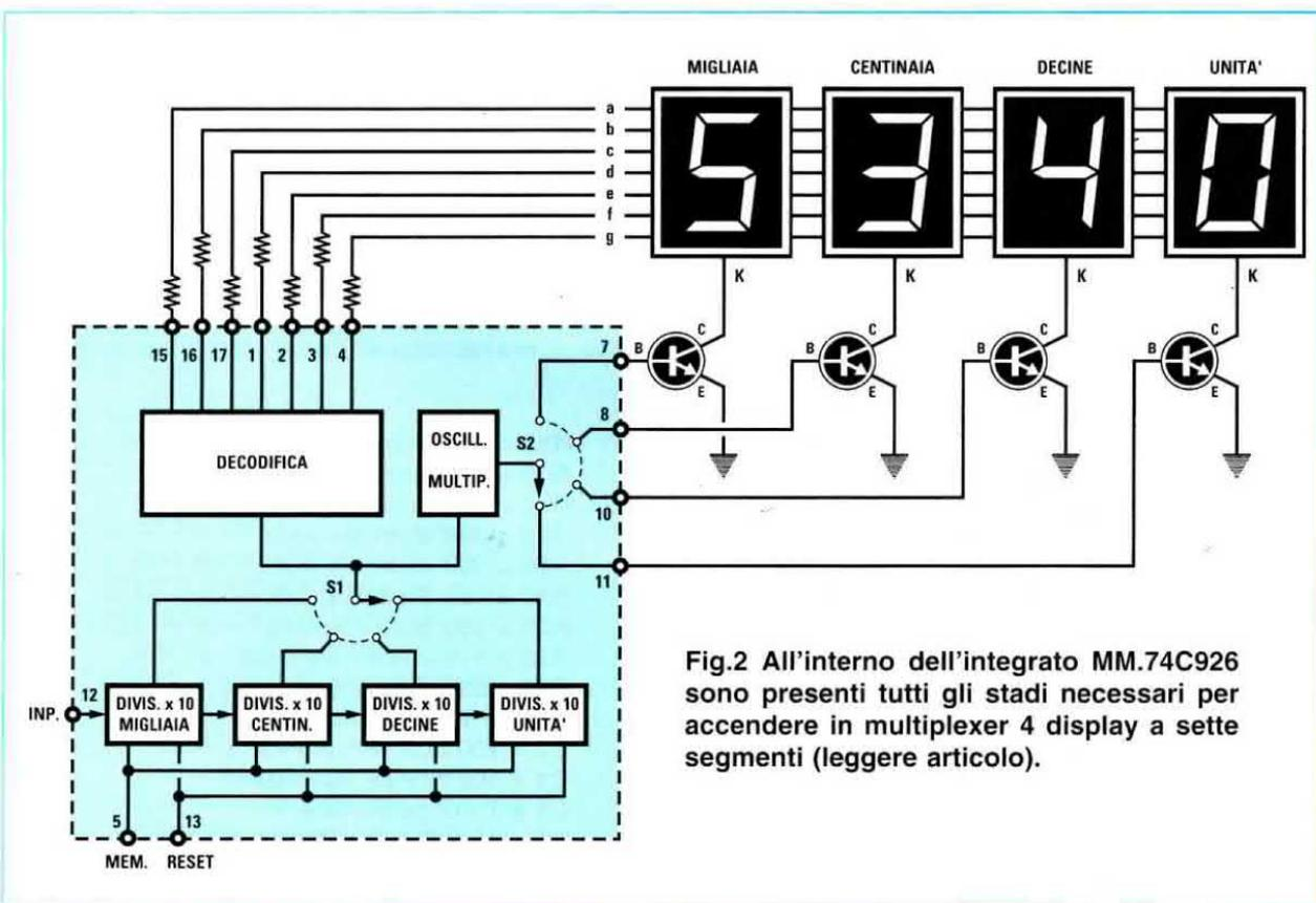
Fig.2 All'interno dell'integrato MM.74C926 sono presenti tutti gli stadi necessari per accendere in multiplexer 4 display a sette segmenti (leggere articolo).
