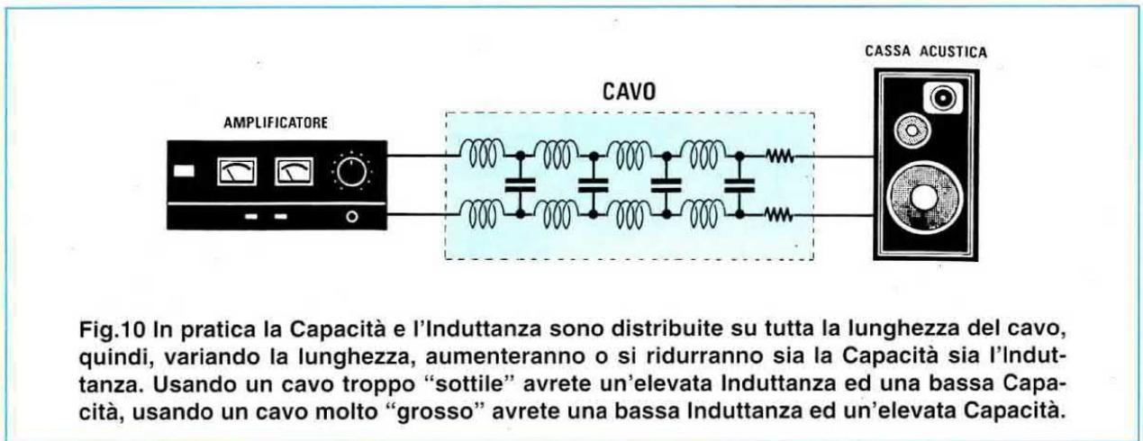
Fig.10 In pratica la Capacità e l'Induttanza sono distribuite su tutta la lunghezza del cavo, quindi, variando la lunghezza, aumenteranno o si ridurranno sia la Capacità sia l'Induttanza. Usando un cavo troppo "sottile" avrete un'elevata Induttanza ed una bassa Capacità, usando un cavo molto "grosso" avrete una bassa Induttanza ed un'elevata Capacità.
