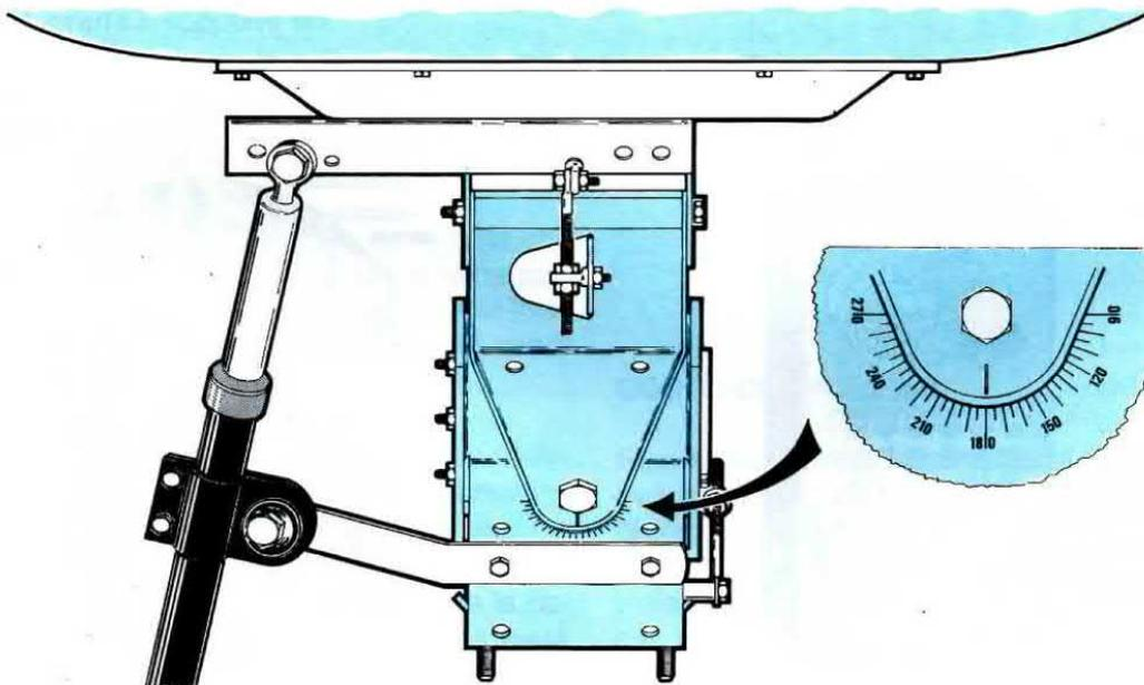
**Fig.14** Per fissare correttamente il motorino sul supporto Polarmount della parabola, dovrete direzionare la parabola verso Sud (180 gradi), poi dovrete sfilare il suo stantuffo a metà corsa, quindi bloccare il suo corpo sulle due barre di sostegno.
