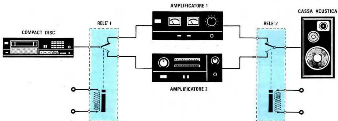
Fig.5 Senza disporre di un'adeguata strumentazione si può controllare la differenza timbrica di due amplificatori usando il sistema della "comparazione in tempo reale", che consiste nel commutare velocemente gli ingressi e le uscite con due relè o deviatori.
