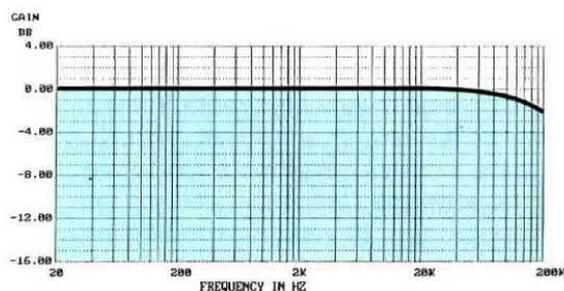
**Fig.13** Se prendete un **Super cavo**, potrete notare che questo inizierà ad attenuare tutte le frequenze superiori ad **80.000 Hz**, ma poiché il nostro orecchio riesce a percepire un massimo di **20.000 Hz** non potremo mai apprezzare questa caratteristica.
