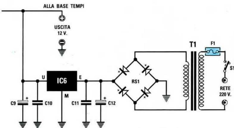
Fig.1 Schema elettrico del contaimpulsì a 4 cifre. Negli esempi riportati a pag.88 potete vedere come collegare gli ingressi per ottenere un preciso contatore, un misuratore di velocità, un cronometro ecc. Dai due terminali posti in alto a destra indicati "alla base tempi" preleverete la tensione di 12 volt per alimentare il kit LX.1189.
