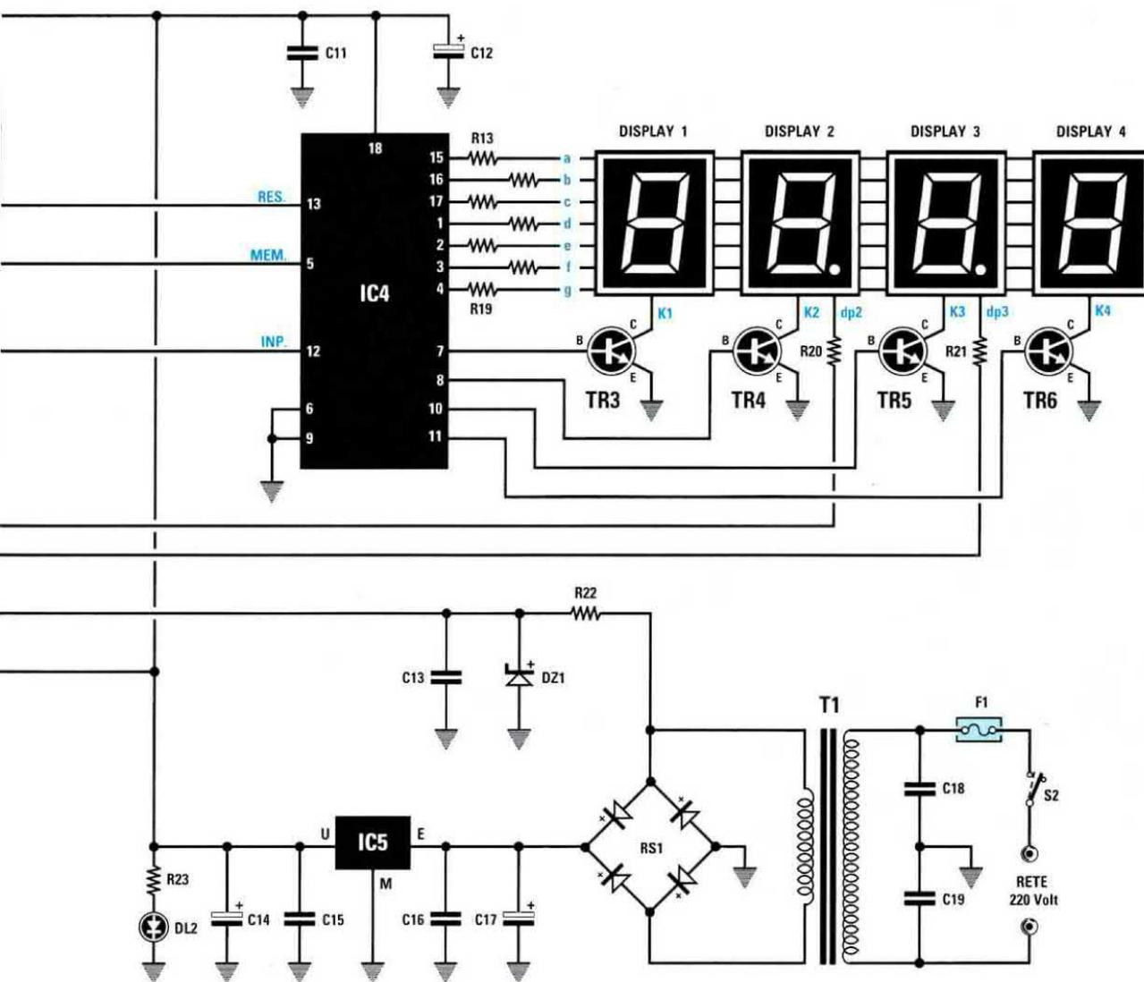
Fig.3 Schema elettrico del frequenzimetro. Anche se questo frequenzimetro è stato progettato per visualizzare un massimo di 1 Megahertz, voi potrete leggere anche frequenze maggiori perdendo nella visualizzazione la sola prima cifra del Megahertz.
