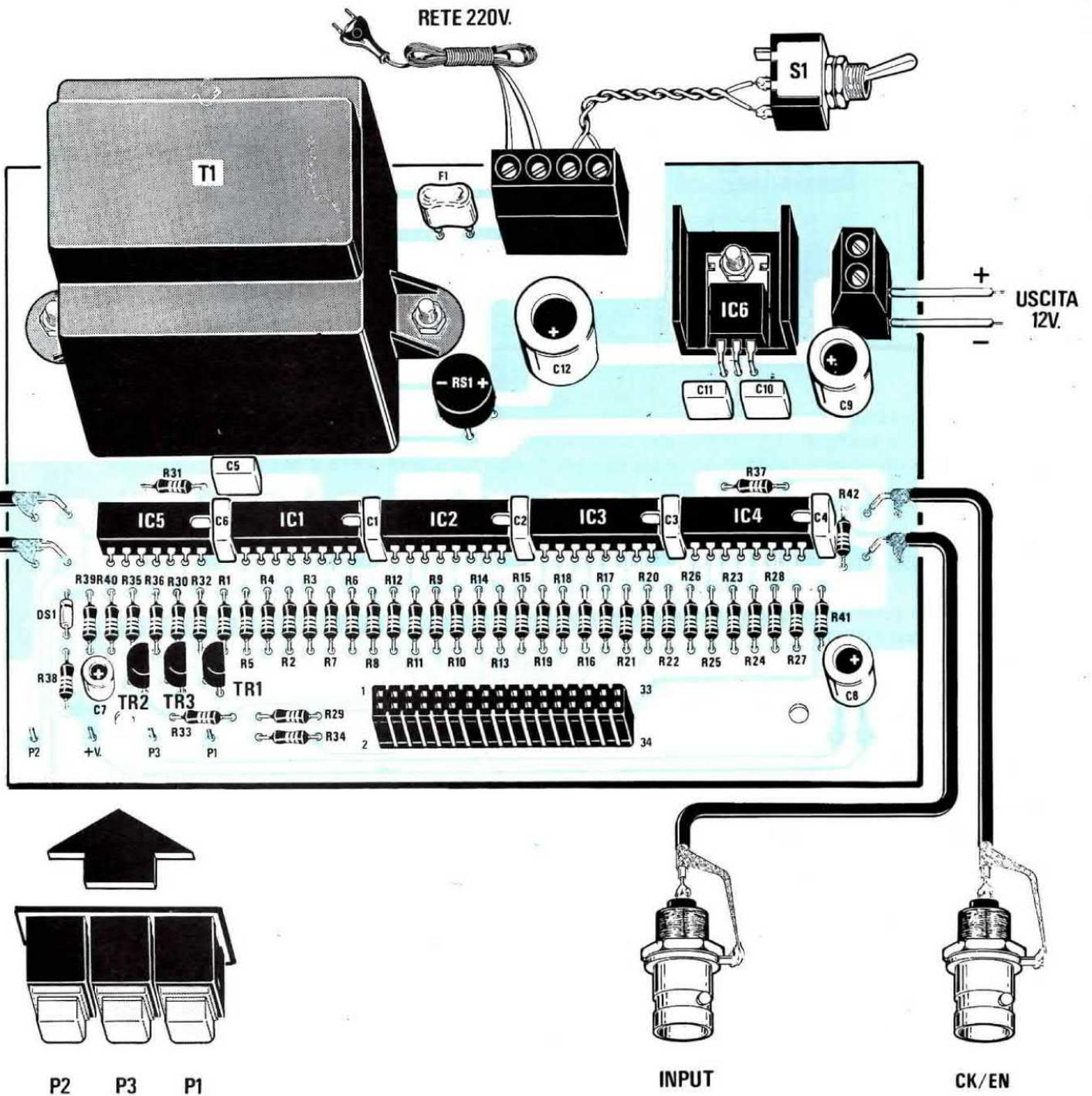
Fig.4 Schema pratico di montaggio del contatore. Conviene stagnare subito la piccola bassetta con sopra già montati i tre pulsanti P2-P3-P1 (vedi in basso) sui quattro terminali a spillo posti sullo stampato LX.1188 contrassegnati con P2 - +V - P3 - P1. Inserire questa bassetta dopo aver montato tutti i componenti sulla scheda base risulta infatti molto più difficile. Nel connettore femmina posto in basso va inserita la scheda dei display.
