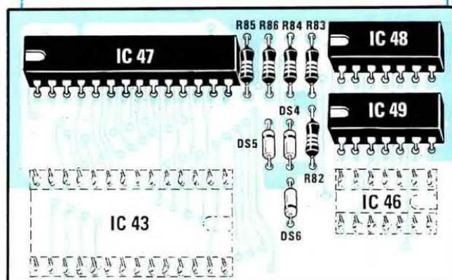
**Fig.3** Schema pratico di montaggio. Rispettate la polarità dei tre diodi al silicio.
