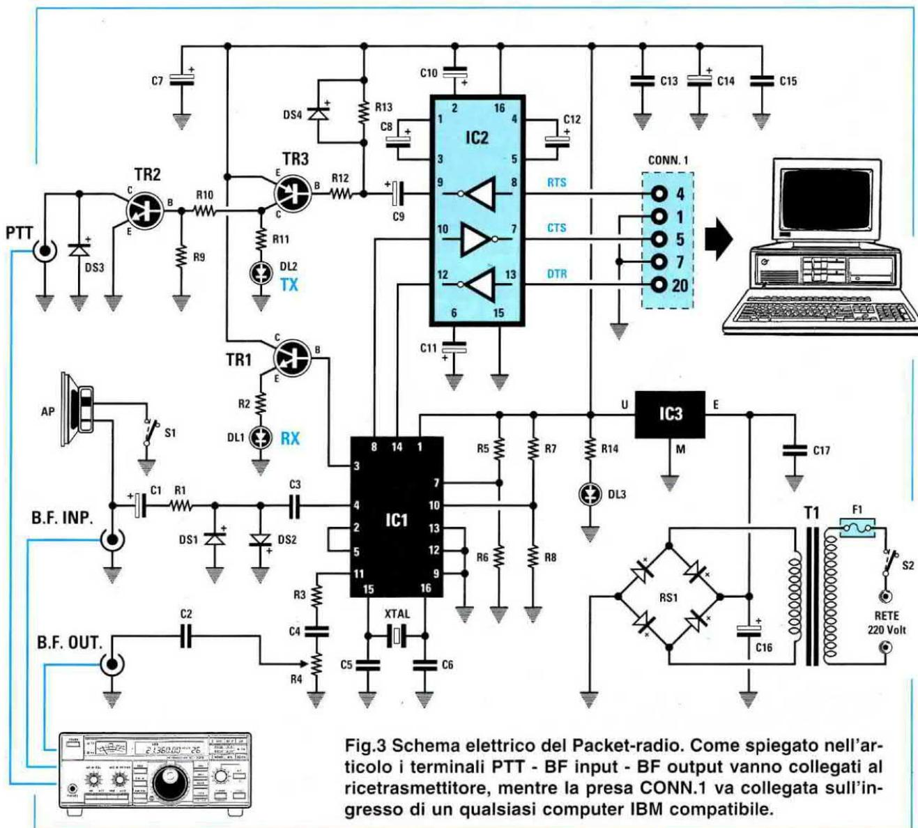
Fig.3 Schema elettrico del Packet-radio. Come spiegato nell'articolo i terminali PTT - BF input - BF output vanno collegati al ricetrasmittitore, mentre la presa CONN.1 va collegata sull'ingresso di un qualsiasi computer IBM compatibile.
