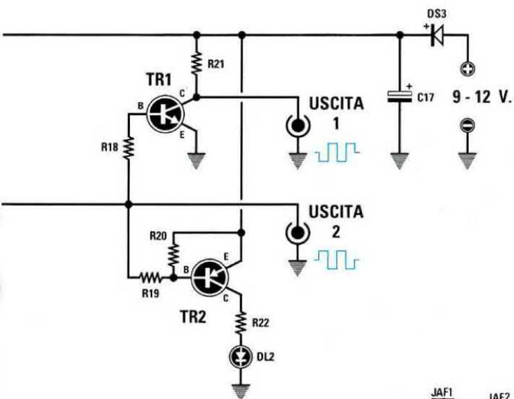
Fig.7 Schema elettrico dello stadio ricevente a raggi infrarossi. Il potenziometro R13 andrà regolato in modo che il diodo led DL2 si SPENGA in assenza di segnali dal trasmettitore. Accendendo il trasmettitore questo diodo led si dovrà ACCENDERE.
