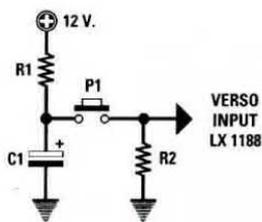
**Fig.8** Per contare quante volte il pulsante P1 o un qualsiasi altro contatto elettrico viene premuto, potete realizzare questo semplice circuito che utilizza due resistenze ed un condensatore elettrolitico. Il circuito va collegato sull'ingresso INPUT assieme al filo di MASSA.
