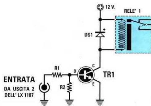
Fig.13 Schema per eccitare un relè con l'uscita 2 del ricevitore.
