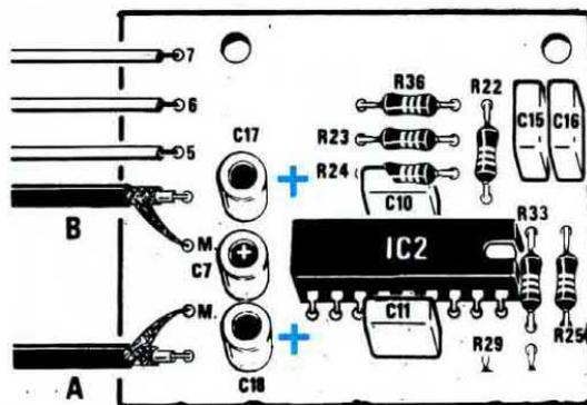
**Fig.3** Se invertirete la polarità dei due elettrolitici C17-C18 migliorerete leggermente le caratteristiche del circuito. Poiché ad orecchio non si nota nessuna differenza, potrete anche non effettuare questa inversione.
