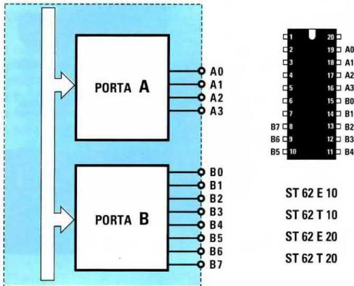
Fig.2 All'interno dei microprocessori ST62 della serie 10-20 sono presenti due PORTE chiamate A-B. Nella porta A troviamo solo quattro piedini Ingressi/Uscita siglati A0-A1-A2-A3, mentre nella porta B troviamo otto piedini siglati da B0 a B7.
