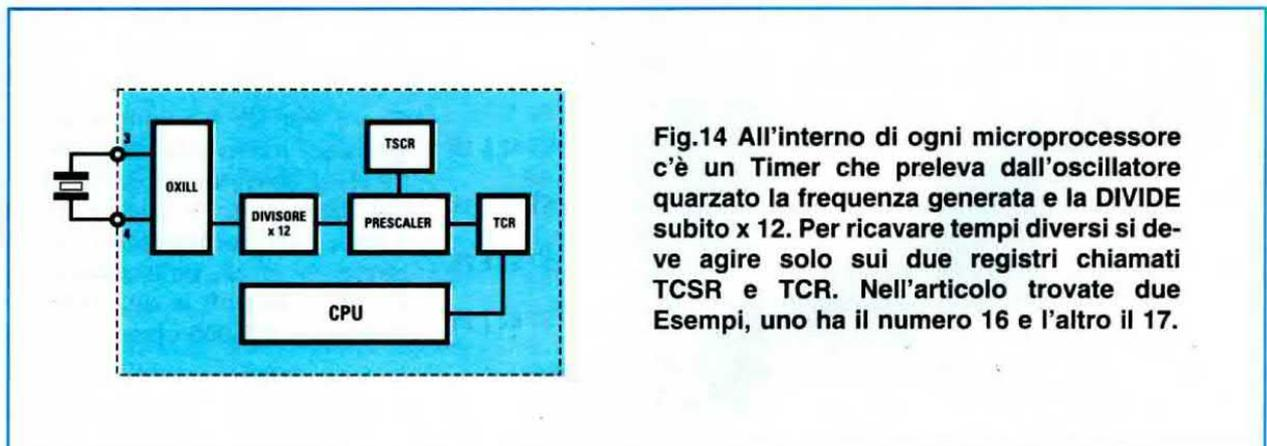
**Fig.14** All'interno di ogni microprocessore c'è un **Timer** che preleva dall'oscillatore quarzato la frequenza generata e la **DIVIDE** subito x 12. Per ricavare tempi diversi si deve agire solo sui due registri chiamati **TCSR** e **TCR**. Nell'articolo trovate due **Esempi**, uno ha il numero 16 e l'altro il 17.
