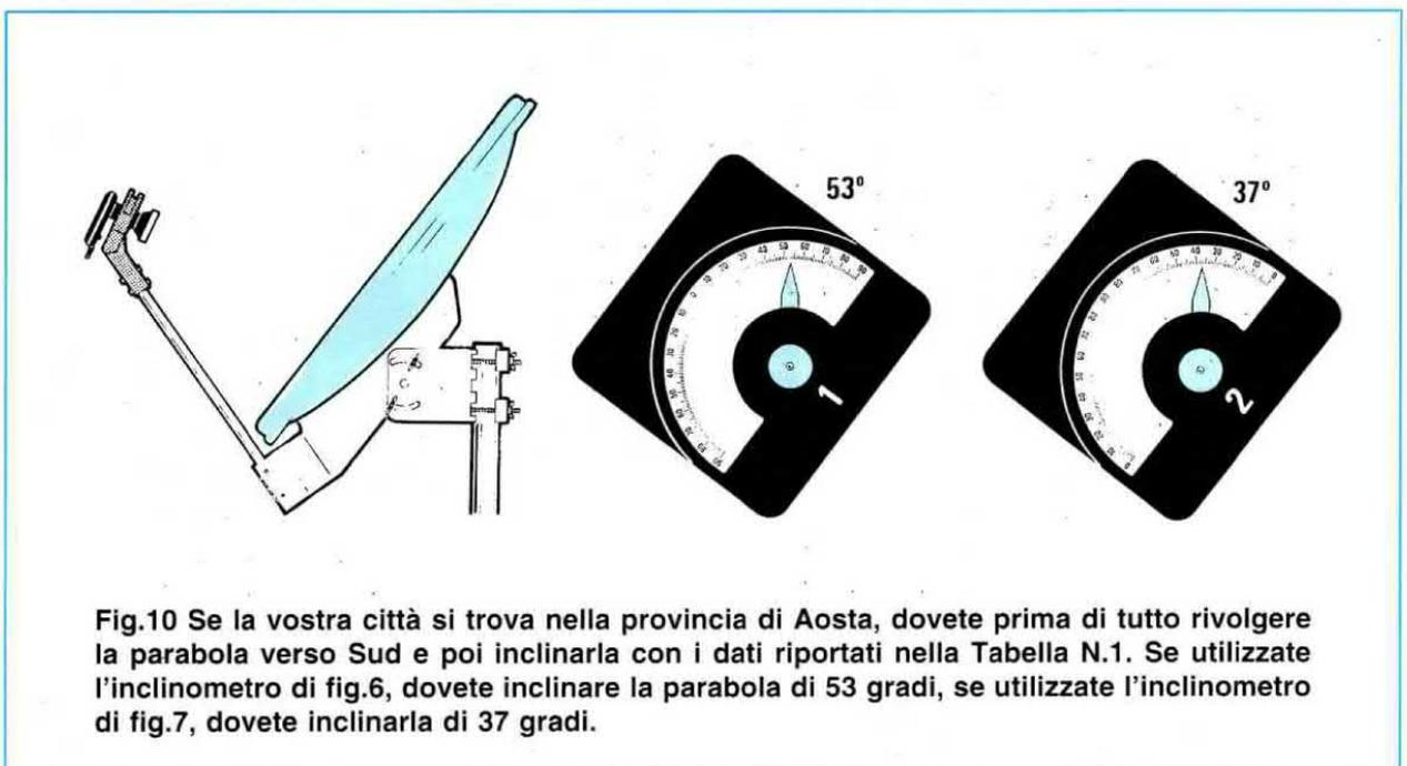
Fig.10 Se la vostra città si trova nella provincia di Aosta, dovete prima di tutto rivolgere la parabola verso Sud e poi inclinarla con i dati riportati nella Tabella N.1. Se utilizzate l'inclinometro di fig.6, dovete inclinare la parabola di 53 gradi, se utilizzate l'inclinometro di fig.7, dovete inclinarla di 37 gradi.
