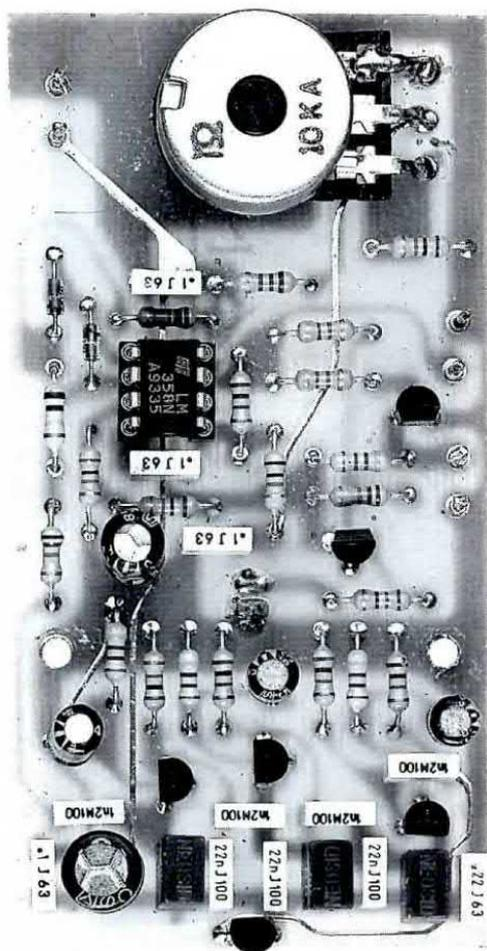
**Fig.9** Foto dello stampato LX.1187 con sopra montati tutti i suoi componenti. Le piste in rame dello stampato risultano protette da una vernice antiossidante e dal lato dei componenti abbiamo tracciato un dettagliato disegno serigrafico.
