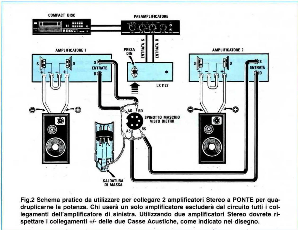
**Fig.2** Schema pratico da utilizzare per collegare 2 amplificatori Stereo a PONTE per quadruplicarne la potenza. Chi userà un solo amplificatore escluderà dal circuito tutti i collegamenti dell'amplificatore di sinistra. Utilizzando due amplificatori Stereo dovrete rispettare i collegamenti +/- delle due Casse Acustiche, come indicato nel disegno.
