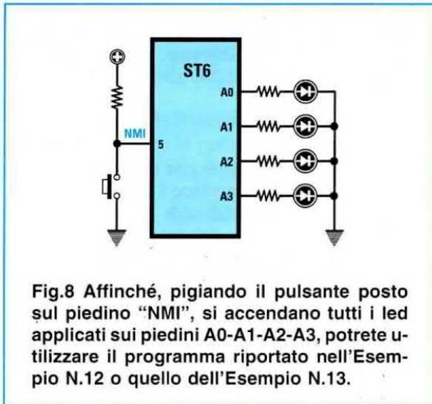
**Esempio N.13** = Nell'esempio N.12 abbiamo riportato un programma che accendeva contemporaneamente **quattro diodi led** pigiando il pulsante collegato sul piedino **NMI** (vedi fig.8). Usando l'accumulatore **A** si ottiene lo stesso risultato, ma bisogna modificare il programma come indicato nell'"Esempio n.13".
