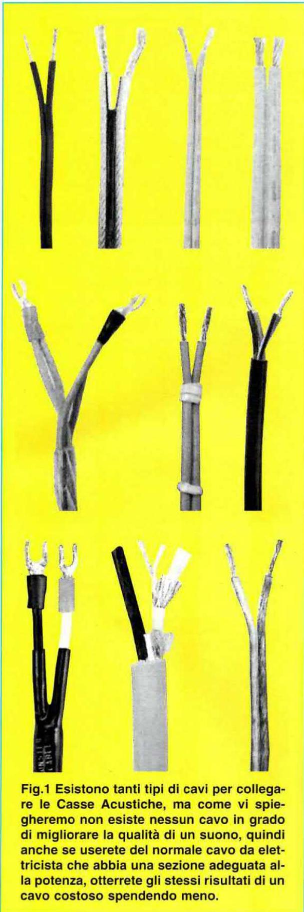
Fig.1 Esistono tanti tipi di cavi per collegare le Casse Acustiche, ma come vi spiegheremo non esiste nessun cavo in grado di migliorare la qualità di un suono, quindi anche se userete del normale cavo da elettricista che abbia una sezione adeguata alla potenza, otterrete gli stessi risultati di un cavo costoso spendendo meno.
