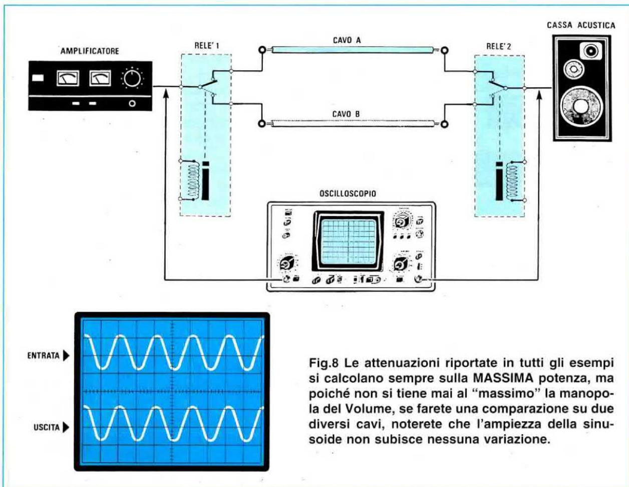
Fig.8 Le attenuazioni riportate in tutti gli esempi si calcolano sempre sulla MASSIMA potenza, ma poiché non si tiene mai al "massimo" la manopola del Volume, se farete una comparazione su due diversi cavi, noterete che l'ampiezza della sinusoide non subisce nessuna variazione.
