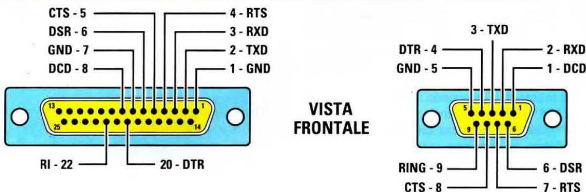
**Fig.6** Per l'uscita abbiamo applicato alla nostra interfaccia una presa seriale a 25 poli, perché è quella più usata. Se nel vostro computer è presente una presa d'ingresso **RS.232** a 9 poli, anziché costruirvi un apposito cordone, vi consigliamo di acquistare una **RIDUZIONE** da 25 a 9 poli, che troverete in qualsiasi negozio per computer.
