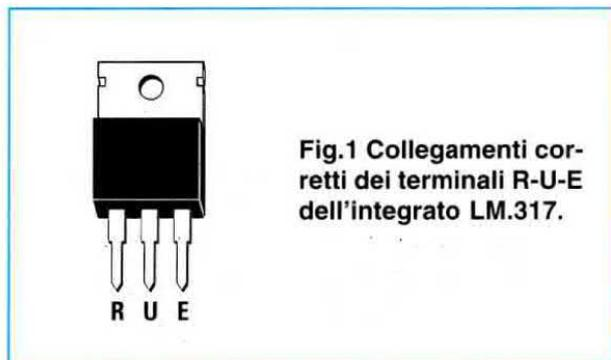
**Fig.1** Collegamenti corretti dei terminali R-U-E dell'integrato LM.317.
