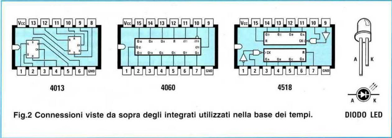
Fig.2 Connessioni viste da sopra degli integrati utilizzati nella base dei tempi.
