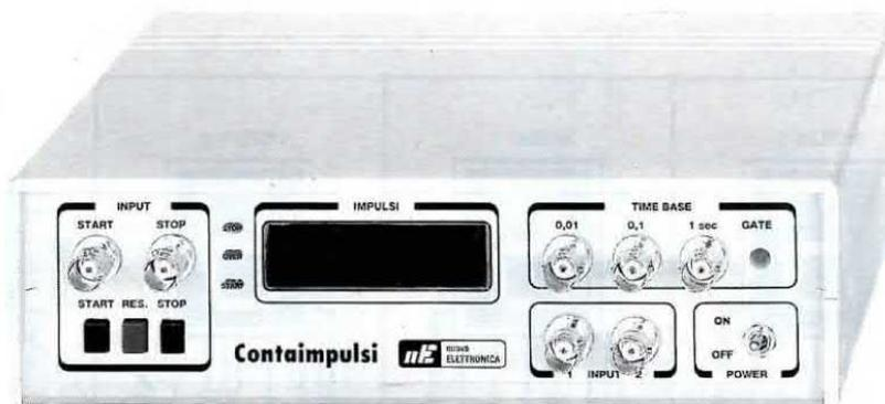
Il contatore che vi presentiamo può essere utilizzato per tantissime applicazioni, ad esempio come "contapezzi" o come "cronometro" oppure per controllare la velocità di piccoli automodelli, sempre che completiate questo circuito con una Base del Tempi oppure con il ricetrasmittitore a raggi infrarossi presentato a pag.78.
