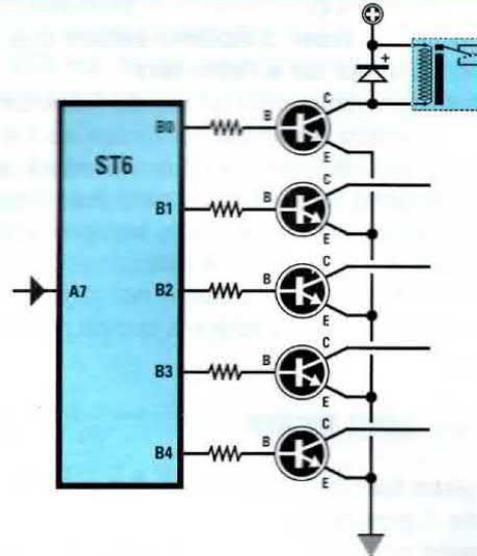
Fig.11 Se vorrete eccitare dei relè dovrete modificare lo schema come qui sopra riportato. Per motivi di spazio abbiamo inserito il relè solo sul primo transistor in alto. Modificando il programma potrete utilizzare come uscite anche tutti gli 8 piedini della Porta B.
