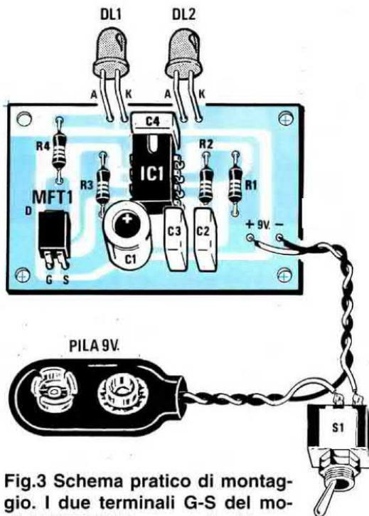
Fig.3 Schema pratico di montaggio. I due terminali G-S del mosfet IRFD.9110 vanno rivolti verso il basso.
