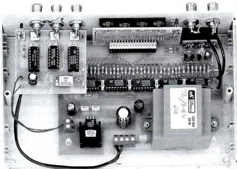
**Fig.7** In questa foto potete vedere la scheda della Base dei Tempi LX.1189 già fissata sui tre bocchettoni (nella fig.6 non era presente). Consigliamo di inserire la scheda LX.1189 all'interno di questo mobile, perché così potrete utilizzare il contatore come cronometro o per misurare delle velocità.
