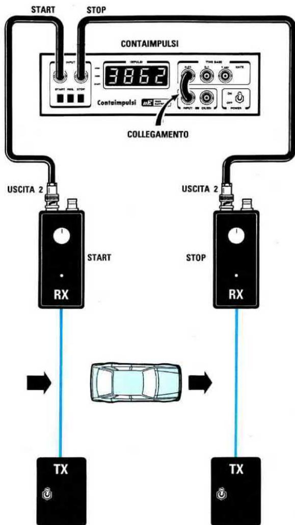
Fig.2 Collocando due trasmettitori e due ricevitori a raggi infrarossi sulla carreggiata di una strada potrete fare dei precisi rilevamenti telemetrici.
