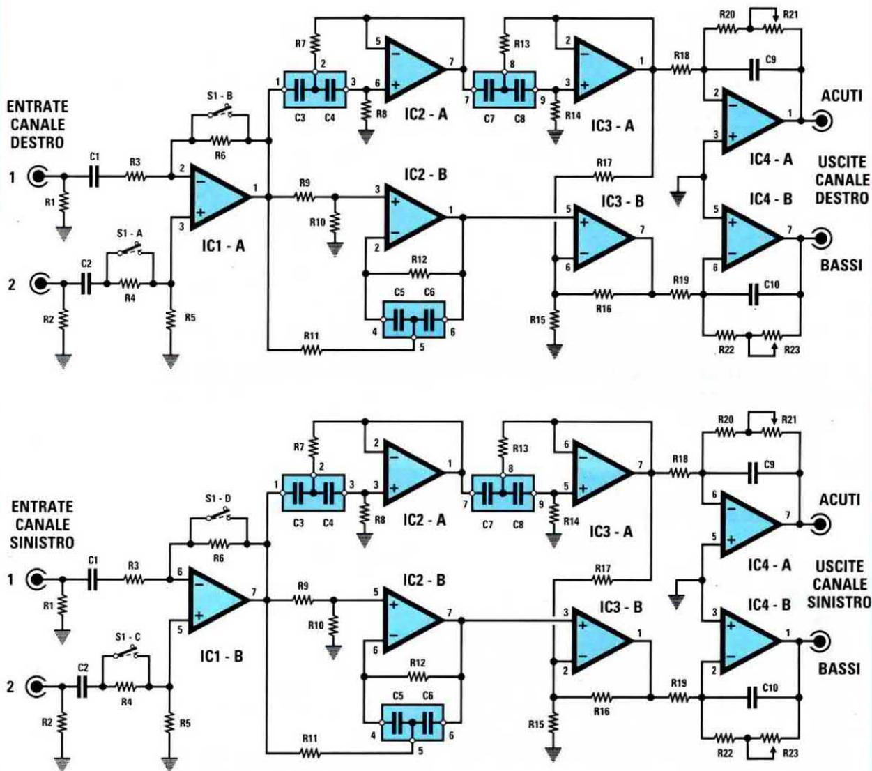
Fig.9 Schema elettrico del Cross-Over elettronico da 24 dB x ottava. I condensatori siglati C3/C4 - C5/C6 - C7/C8, tutti della stessa capacità, inseriti nei due stampati di fig.16 vi permetteranno di variare con estrema facilità la frequenza di taglio. Il circuito accetta sull'ingresso dei segnali "bilanciati" ed anche dei normali "sbilanciati" entrando sul solo "ingresso 2" e cortocircuitando le resistenze R4-R6.
