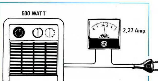
**Fig.3** Conoscendo la corrente assorbita da un carico "resistivo" e moltiplicando gli Amper per i 220 Volt otterrete  $2,27 \times 220 = 499,4$  Watt. Non ottenete 500 Watt perché gli Amper sarebbero 2,272727.
