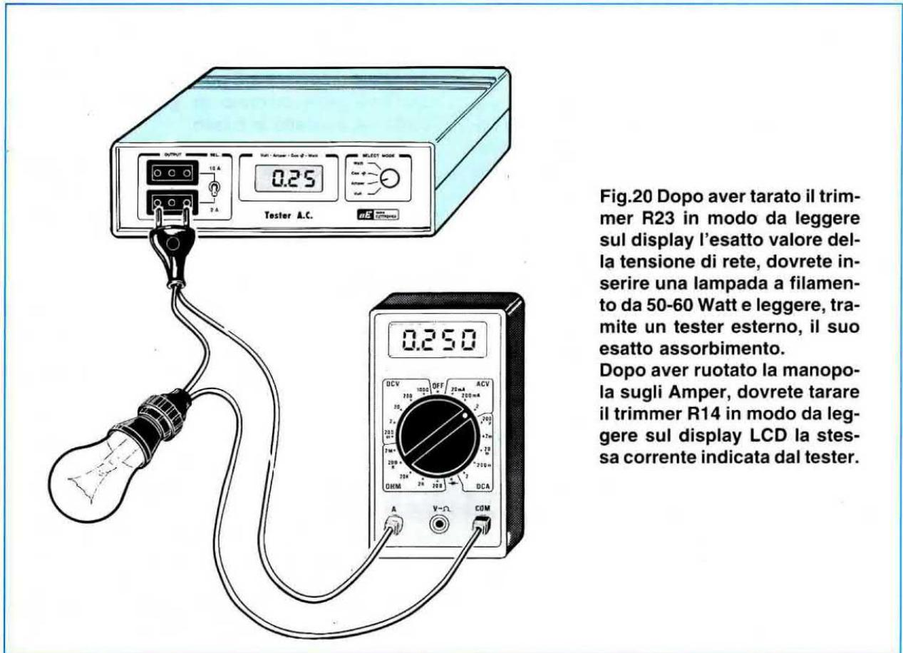
Fig.20 Dopo aver tarato il trimmer R23 in modo da leggere sul display l'esatto valore della tensione di rete, dovrete inserire una lampada a filamento da 50-60 Watt e leggere, tramite un tester esterno, il suo esatto assorbimento. Dopo aver ruotato la manopola sugli Amper, dovrete tarare il trimmer R14 in modo da leggere sul display LCD la stessa corrente indicata dal tester.
