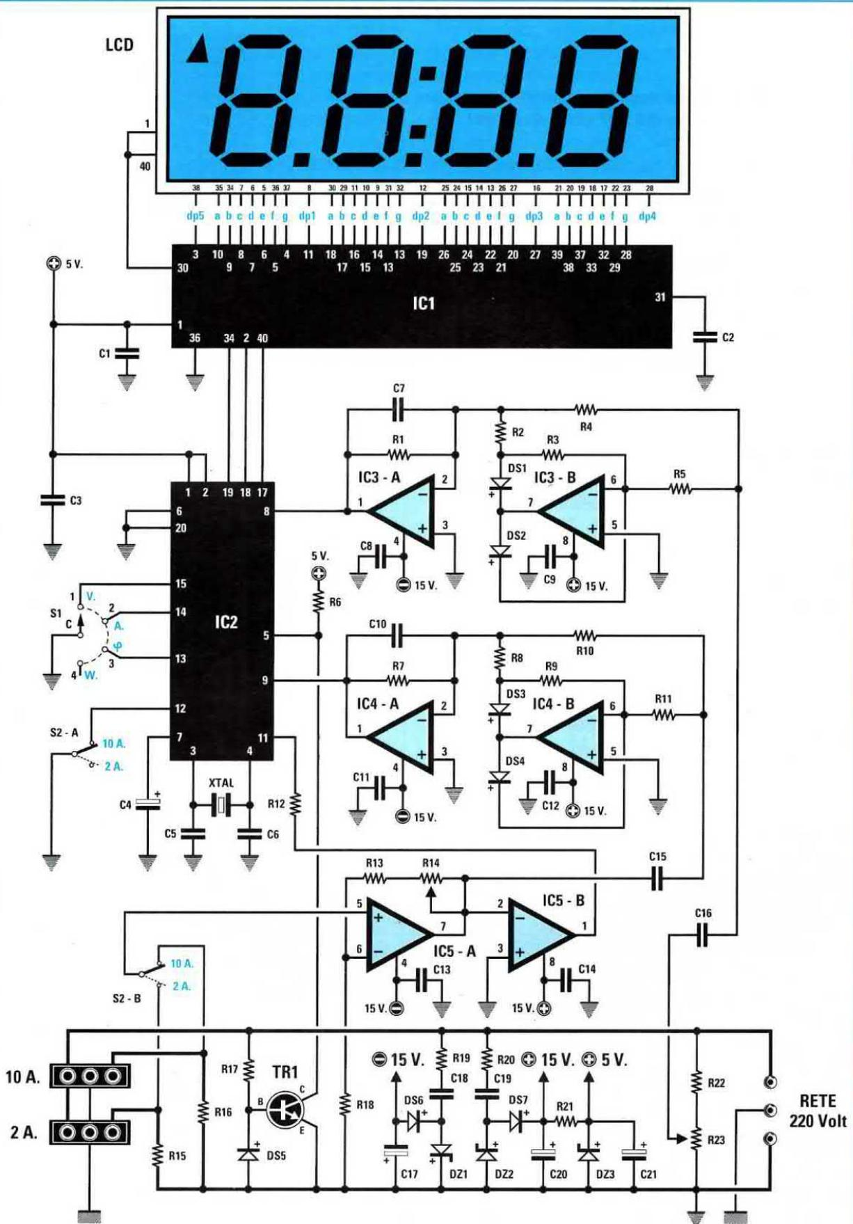
Fig.8 Schema elettrico dell'Analizzatore di rete.
