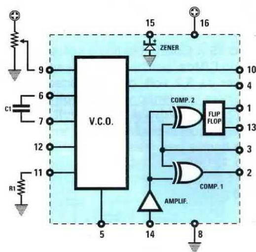
Fig.1 Schema a blocchi degli stadi presenti all'interno del 4046 e connessioni dello zoccolo viste da sopra. Sul piedino 15 degli integrati HC/Mos e HC/TTL non è presente il diodo zener.
