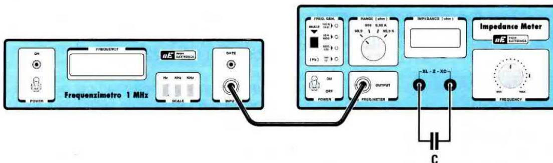
Fig.39 Con questo stesso impedenzometro potrete conoscere l'esatto valore di un qualsiasi condensatore che abbia una capacità non minore di 1.000 picroFarad o maggiore di 2.000 microFarad. NOTA = Prima di inserire sui morsetti un qualsiasi condensatore dovrete SCARICARLO.
