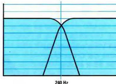
**Fig.5** Se la tolleranza dei componenti spostasse la frequenza di taglio del Passa/Basso, si sposterebbe automaticamente anche la frequenza di taglio del Passa/Alto.
