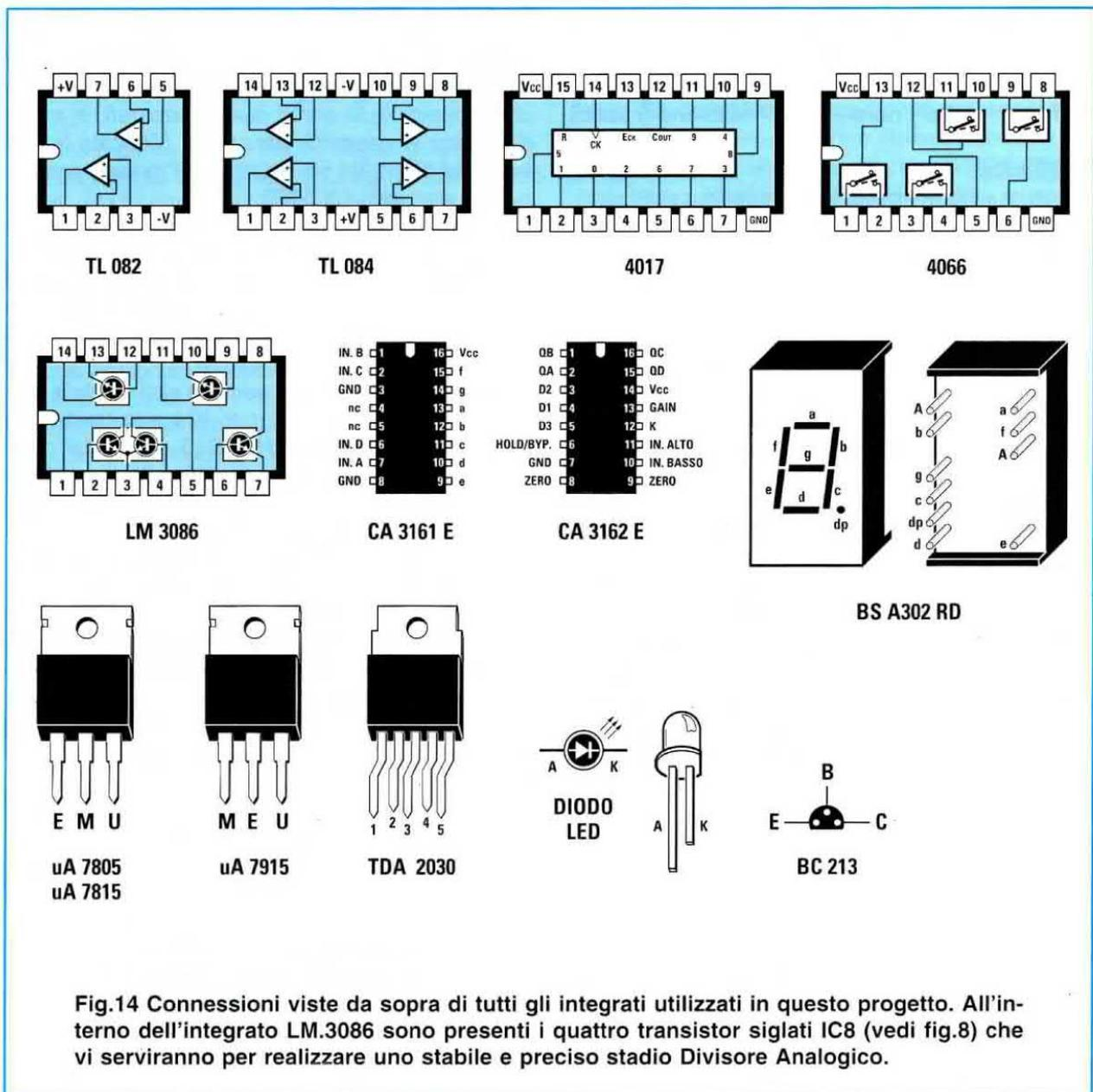
Fig.14 Connessioni viste da sopra di tutti gli integrati utilizzati in questo progetto. All'interno dell'integrato LM.3086 sono presenti i quattro transistor siglati IC8 (vedi fig.8) che vi serviranno per realizzare uno stabile e preciso stadio Divisore Analogico.
