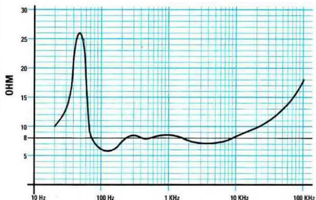
**Fig.25** Grafico di una Cassa Acustica a 2 Vie. Questa Cassa esalta leggermente tutte le frequenze dei Bassi comprese tra gli 80 ed i 180 Hz ed attenua le frequenze degli Acuti sopra i 20.000 Hz. L'aumento d'impedenza sui 40 Hz circa è generato dalla frequenza di risonanza del cono del Woofer.
