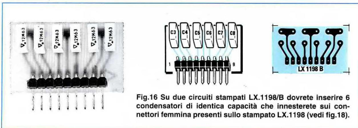
Fig.16 Su due circuiti stampati LX.1198/B dovrete inserire 6 condensatori di identica capacità che innesterete sui connettori femmina presenti sullo stampato LX.1198 (vedi fig.18).
