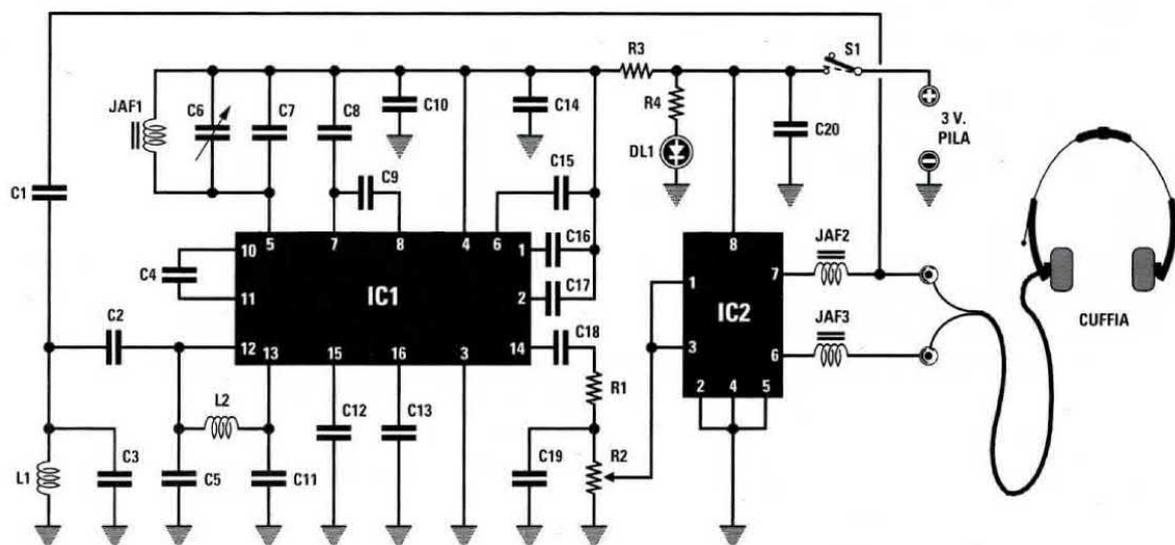
Fig.5 Schema elettrico del ricevitore che forniamo già montato e tarato sui 67,10 MHz.
