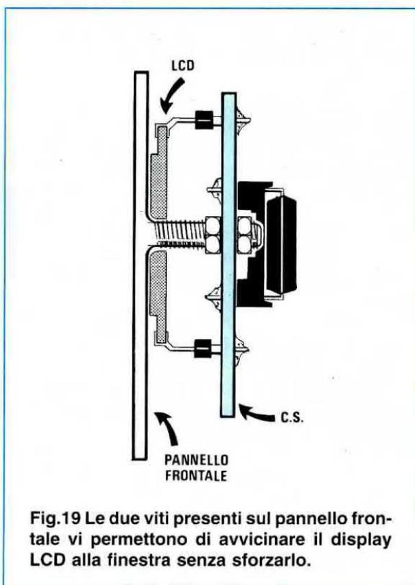
**Fig.19** Le due viti presenti sul pannello frontale vi permettono di avvicinare il display LCD alla finestra senza sforzarlo.
