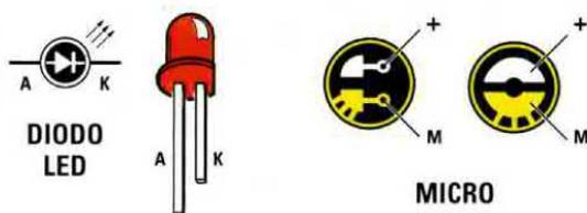
Fig.7 Il terminale più lungo del diodo led è sempre l'Anodo. Per il microfono, la pista di "massa" va rivolta verso il foro M stampigliato sulla destra del circuito stampato come visibile in fig.9.
