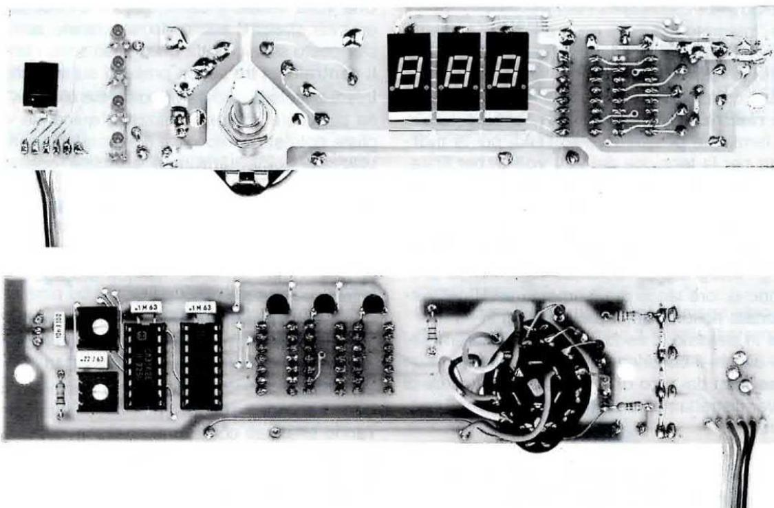
**Fig.12** Foto dello stampato LX.1192/B visto dal lato dei display e dal lato dei componenti. Se eseguite delle perfette stagnature questo strumento funzionerà all'istante.
