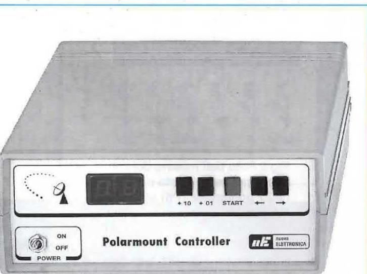
Fig.1 I due pulsanti di sinistra presenti sul pannello vi serviranno per impostare la posizione in cui la parabola dovrà direzionarsi. Il pulsante di Start serve per far partire il motorino ed i due pulsanti di destra per spostare di pochi millimetri la parabola verso destra o verso sinistra.
