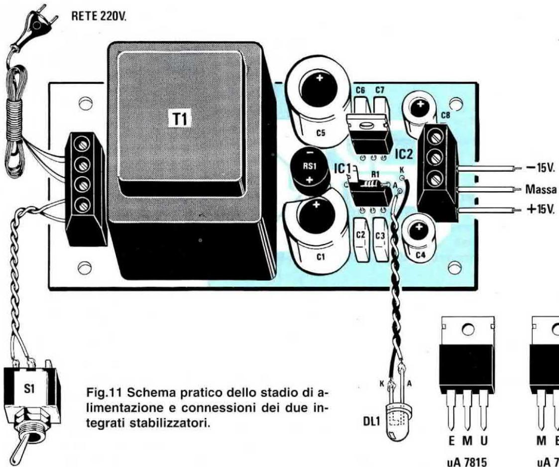
Fig.11 Schema pratico dello stadio di alimentazione e connessioni dei due integrati stabilizzatori.
