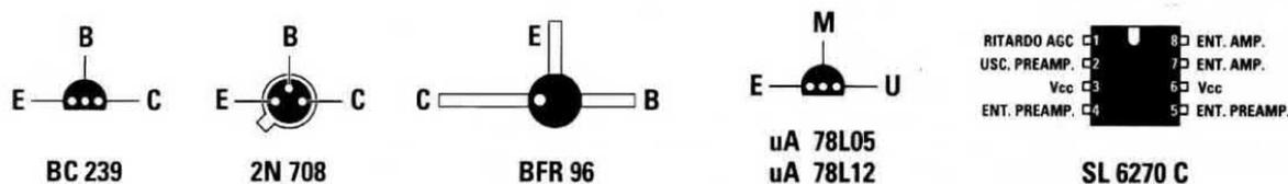
Fig.2 Connessioni dei terminali dei transistor e dell'integrato SL.6270.
