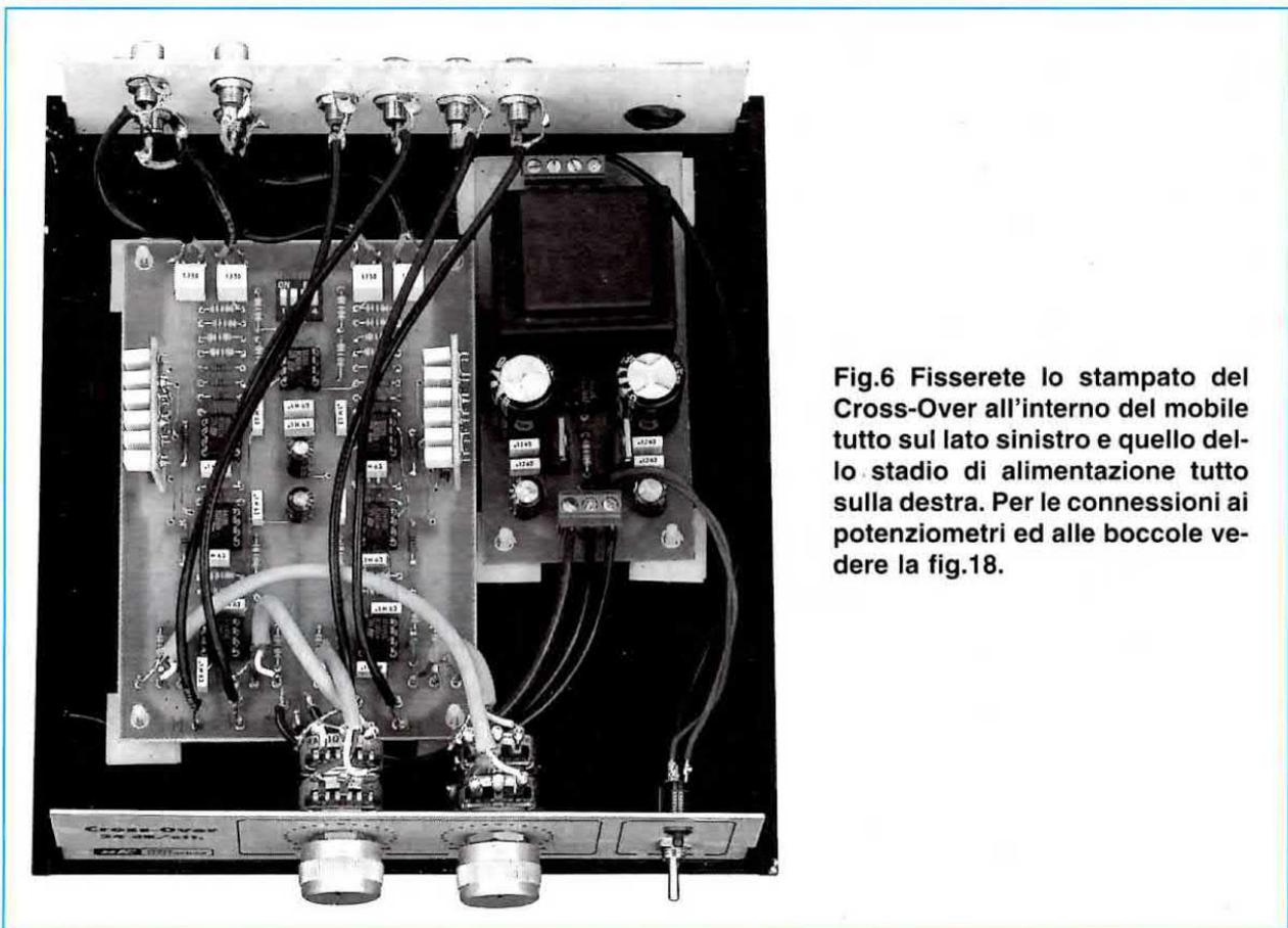
Fig.6 Fisserete lo stampato del **Cross-Over** all'interno del mobile tutto sul lato sinistro e quello dello stadio di alimentazione tutto sulla destra. Per le connessioni ai potenziometri ed alle bocche vedere la fig.18.
