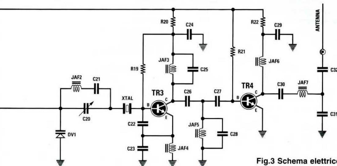
Fig.3 Schema elettrico del trasmettitore.
