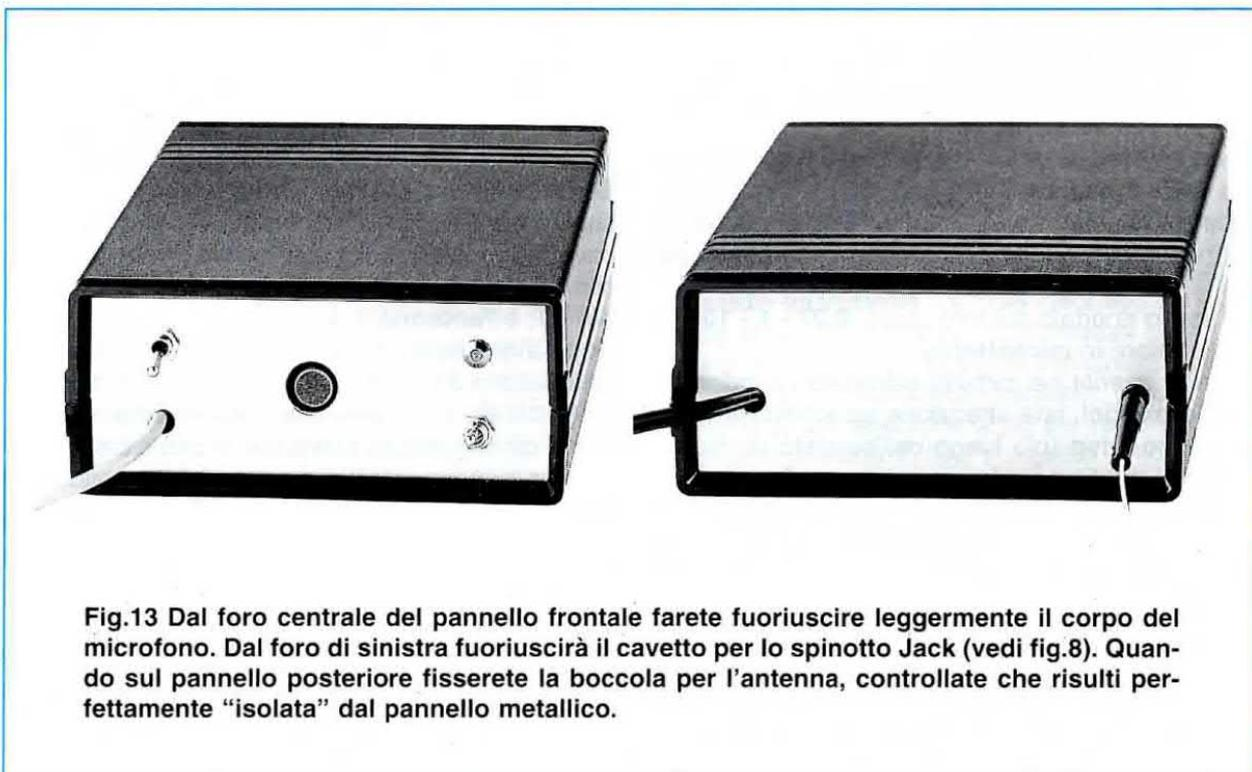
**Fig.13** Dal foro centrale del pannello frontale farete fuoriuscire leggermente il corpo del microfono. Dal foro di sinistra fuoriuscirà il cavetto per lo spinotto Jack (vedi fig.8). Quando sul pannello posteriore fisserete la boccola per l'antenna, controllate che risulti perfettamente "isolata" dal pannello metallico.
