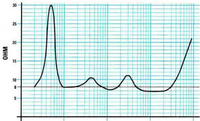
**Fig.26** Grafico di una Cassa Acustica a 3 Vie. I due picchi visibili sui 400 Hz e sui 3.000 Hz sono generati dalla frequenza di taglio del filtro Cross-Over. Il Tweeter di questa Cassa lavora correttamente perché la sua impedenza sale a 10 ohm solo oltre i 30.000 Hz circa.
