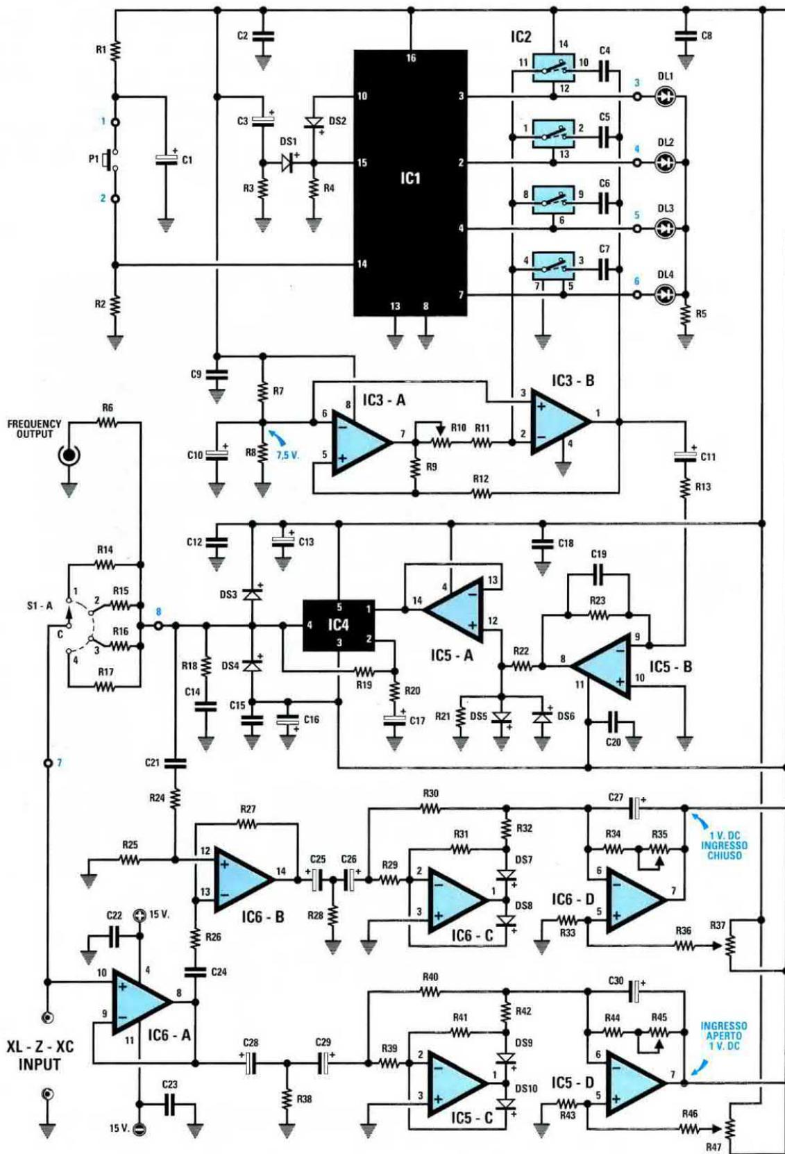
Fig.8 Schema elettrico dell'impedenzometro-reattanzometro.
