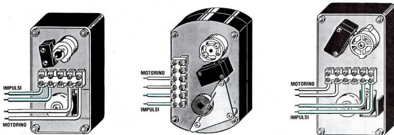
Fig.12 All'interno dei motorini a pistone troverete una morsettieria per i due fili di alimentazione e per i due fili degli impulsi di comando per il Box. Se applicherete sui morsetti "impulsi" la tensione del motorino, brucerete i contatti del reed-relè. In questo disegno potete vedere su quali morsetti collegare i fili di alimentazione e su quali prelevare gli impulsi.
