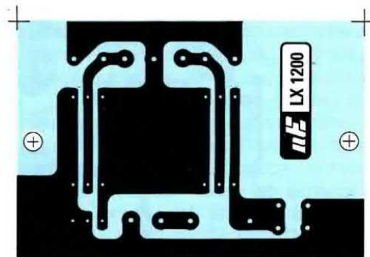
Fig.15 Schema pratico dell'alimentatore CC/CC e disegno a grandezza naturale del circuito stampato visto dal lato rame. Spostando il ponticello J1 verso C o A riuscirete ad eliminare gli eventuali disturbi spuri generati dall'impianto auto.
