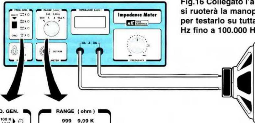
Fig.16 Collegato l'altoparlante sui morsetti, si ruoterà la manopola Range su 99,9 ohm per testarlo su tutta la gamma Audio da 17 Hz fino a 100.000 Hz.
