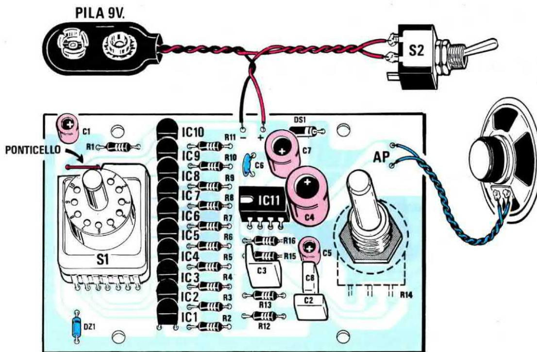
Fig.6 Schema pratico di montaggio del generatore di melodie. Non dimenticatevi di inserire nei due fori dello stampato, presenti sopra il commutatore S1, il "ponticello" in filo di rame nudo. Rivolgete la fascia di riferimento dei due diodi DS1 e DZ1 come visibile nel disegno e quando inserite gli integrati musicali non accorciate i loro terminali.
