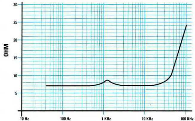
Fig.18 Controllando un altoparlante per Medi-Bassi noterete che la sua impedenza rimane entro una tolleranza di un 15% in più o in meno. L'aumento d'impedenza visibile sui 200-300 Hz corrisponde alla frequenza di "risonanza" meccanica del cono.
