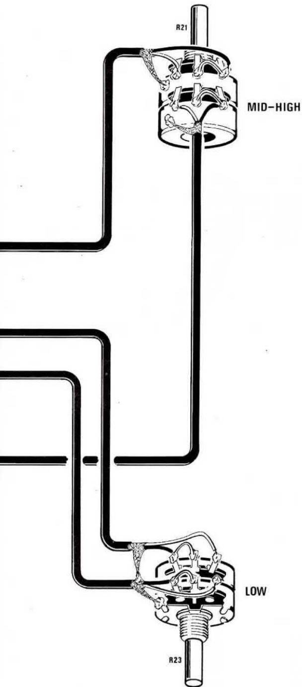
Fig.18 Schema pratico di montaggio del Cross-Over STEREO da 24 dB x ottava. Se entrate con un segnale "sbilanciato", applicatelo sul solo ingresso 2 spostando tutte le leve del dip-switch S1 verso sinistra. Nei connettori femmina dovreste inserire i circuiti di fig.16 senza preoccuparvi del loro verso in quanto reversibili. Non sbagliatevi a collegare i fili dei cavetti schermati ai potenziometri e non surriscaldate troppo questi cavetti per non fondere l'isolante interno.
