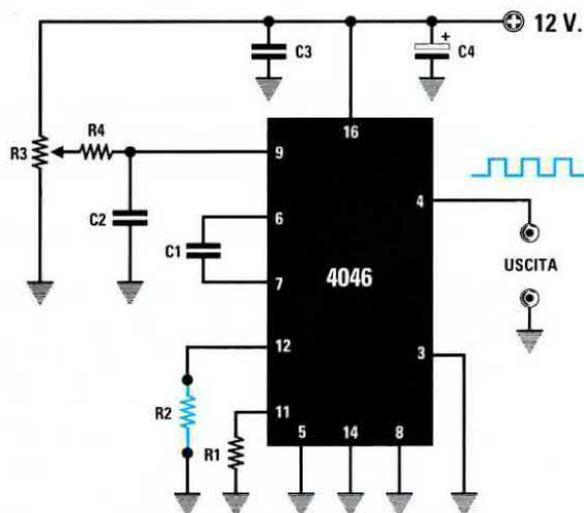
Fig.5 La resistenza applicata tra il piedino 12 e la massa (vedi R2) ci permette di prefissare la frequenza "minima" a cui il VCO può scendere. Se non inseriamo nessuna resistenza, il VCO inizierà a diventare instabile quando ruoteremo il trimmer R3 verso la tensione minima.
