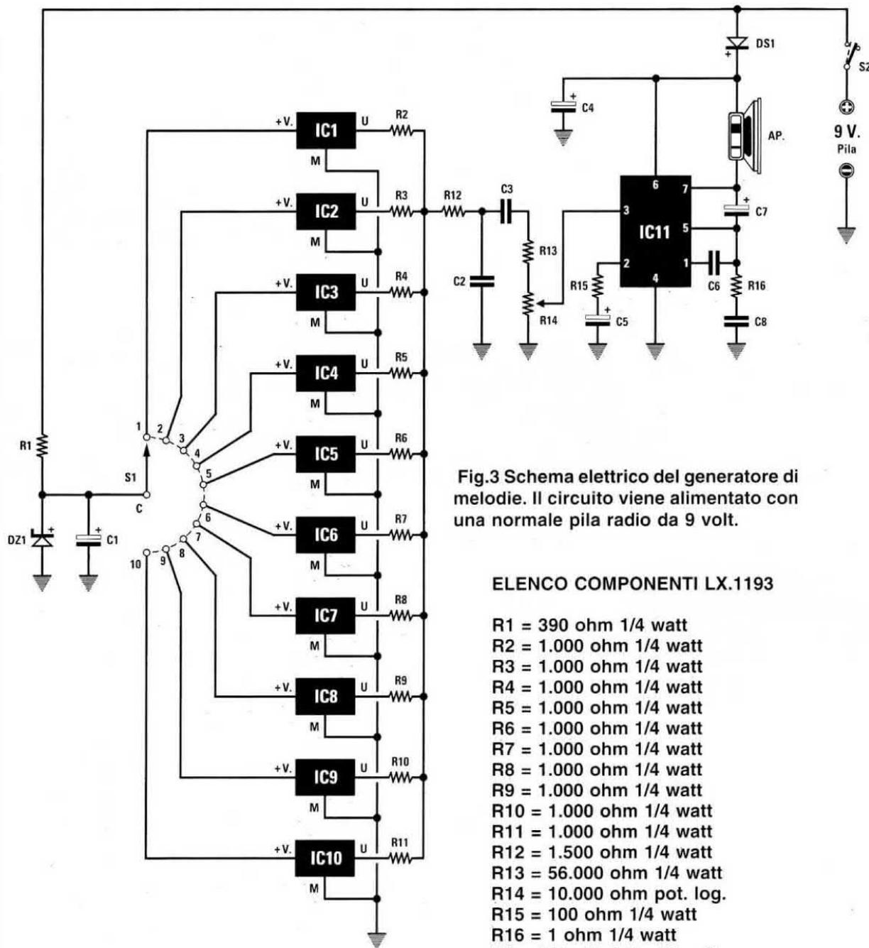
Fig.3 Schema elettrico del generatore di melodie. Il circuito viene alimentato con una normale pila radio da 9 volt.
