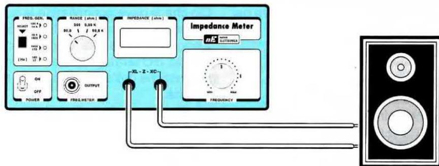
**Fig.24** Per controllare l'impedenza di una Cassa Acustica, collegatela sull'ingresso dell'impedenzometro poi, partendo dalla sua frequenza più bassa dei 20 Hz, salite fino a 100.000 Hz. Per leggere la frequenza potrete usare un Frequenzimetro (vedi fig.37).
