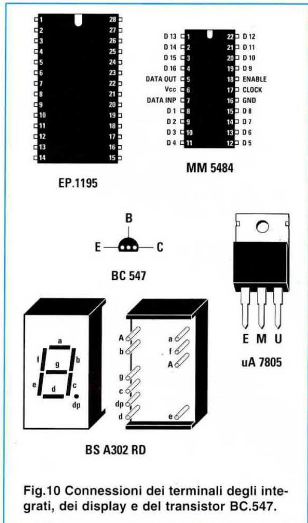
Fig.10 Connessioni dei terminali degli integrati, dei display e del transistor BC.547.
