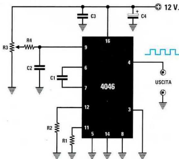
Fig.4 Il VCO interno dell'integrato 4046 essendo molto stabile e perfettamente lineare ci permette di realizzare dei semplici Generatori di Onde Quadre utilizzando pochissimi componenti. Una volta scelta la capacità del condensatore C1 (vedi Tabella N.2) per variare la frequenza dovremo semplicemente ruotare il cursore del trimmer R3.
