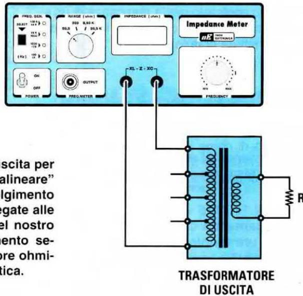
Fig.28 Per verificare se un trasformatore d'uscita per valvole termoioniche risulta veramente "ultralineare" dovete collegare le due estremità dell'avvolgimento "primario" (quelle che in pratica vanno collegate alle Placche delle valvole finali) agli ingressi del nostro Impedenzometro ed applicare sull'avvolgimento secondario una resistenza R che abbia un valore ohmico identico all'impedenza della Cassa Acustica.
