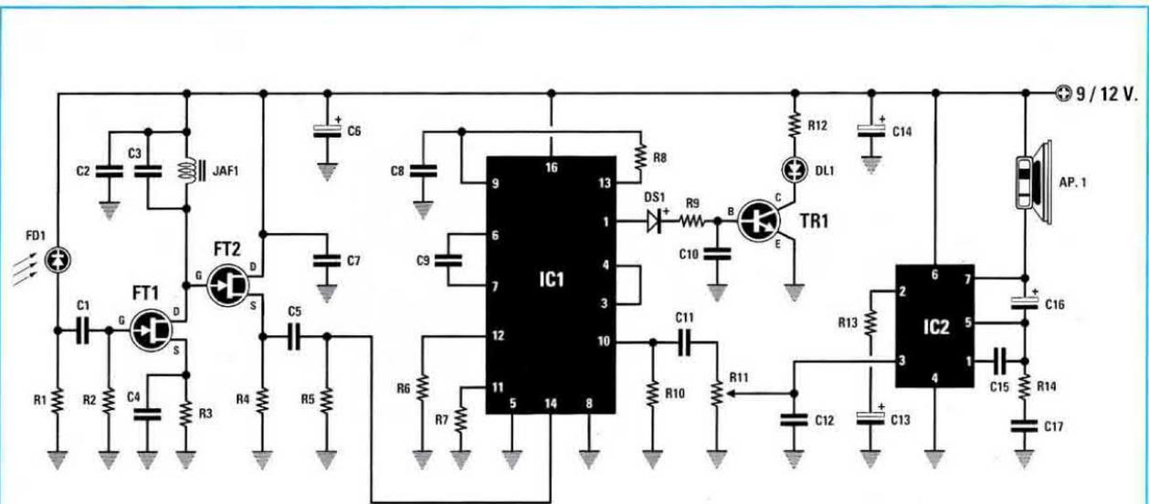
Fig.12 Schema elettrico del ricevitore a Raggi Infrarossi. Rivolgendo il diodo FD1 verso i diodi trasmettenti, dovrà accendersi il diodo led DL1 applicato su TR1.
