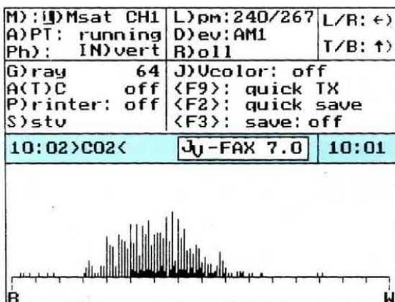
Fig.3 Nella finestra di ricezione appaiono l'ora dell'immagine che il satellite sta inviando o invierà e a destra l'ora in GMT su cui è regolato il vostro computer. Se quest'ultima non appare premete F.
