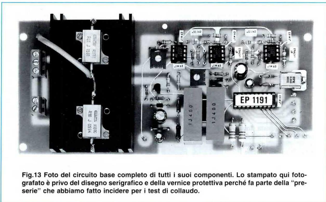
**Fig.13** Foto del circuito base completo di tutti i suoi componenti. Lo stampato qui fotografato è privo del disegno serigrafico e della vernice protettiva perché fa parte della "pre-serie" che abbiamo fatto incidere per i test di collaudo.
