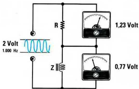
Fig.4 Se eleviamo la frequenza da 100 Hz a 1.000 Hz, noteremo che ai capi della resistenza R risulta presente una tensione di 1,23 volt ed ai capi dell'induttanza Z una tensione di 0,77 volt.
