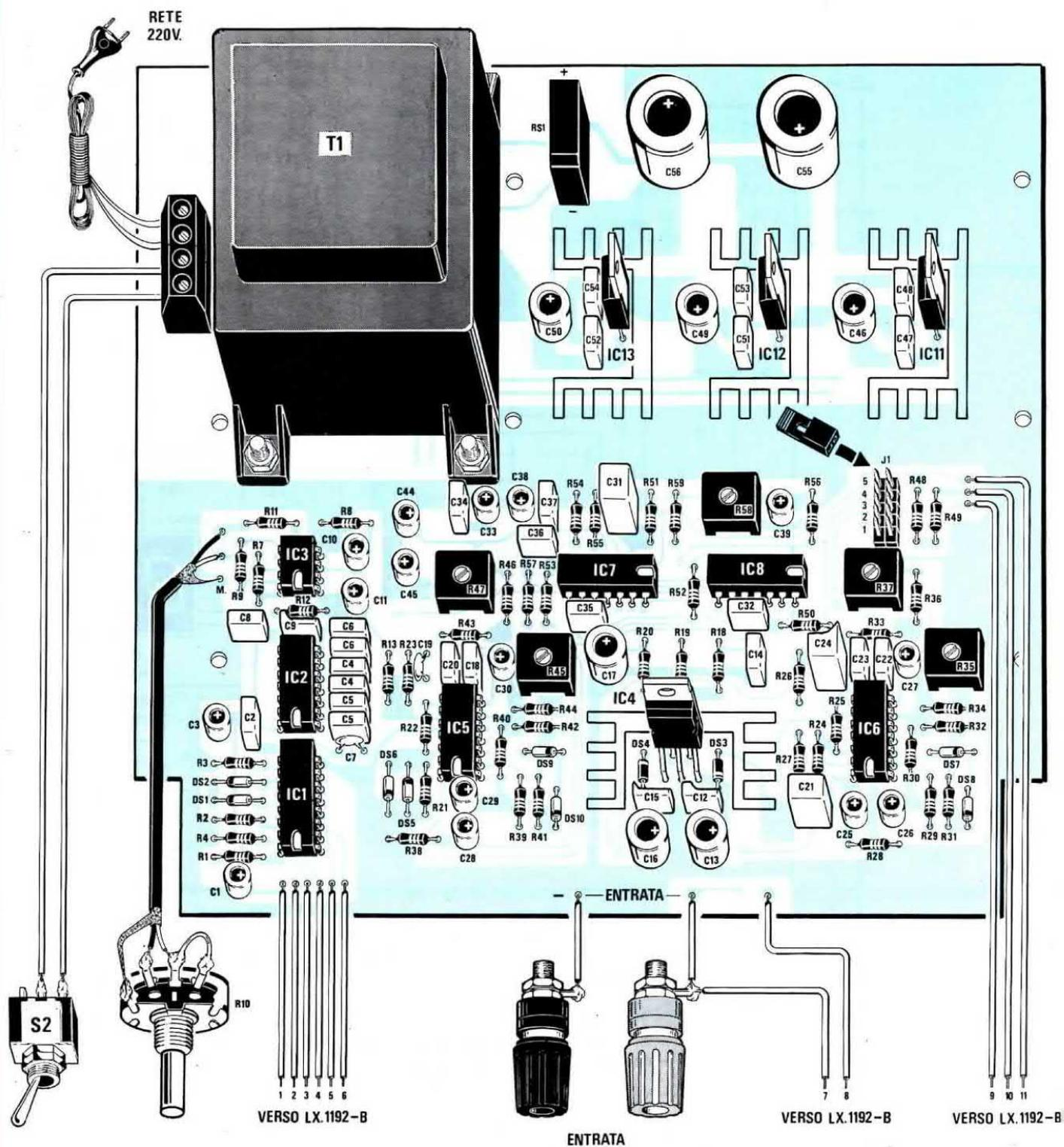
Fig.9 Schema pratico di montaggio della scheda base LX.1192. I terminali dei fili posti in basso vanno collegati allo stampato LX.1192/B che appare nel disegno di fig.11.
