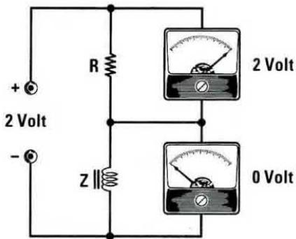
Fig.2 Se applichiamo 2 volt "continui" ad un'induttanza da 1 millih con in serie una resistenza da 10 ohm, rileveremo ai capi di R una tensione di 2 volt e ai capi di Z una tensione di 0 volt.
