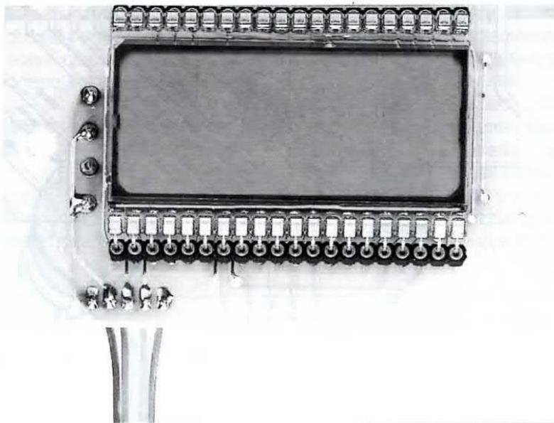
Fig.17 Dal lato del display dovete inserire nello stampato due strip da 20 contatti che utilizzerete come zoccolo.
