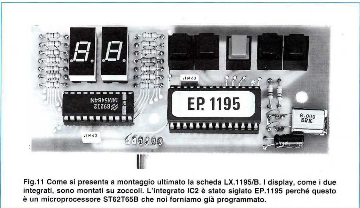
Fig.11 Come si presenta a montaggio ultimato la scheda LX.1195/B. I display, come i due integrati, sono montati su zoccoli. L'integrato IC2 è stato siglato EP.1195 perché questo è un microprocessore ST62T65B che noi forniamo già programmato.
