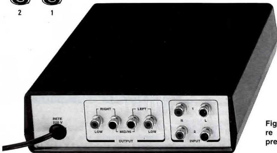
Fig.17 Sul pannello posteriore sono presenti le quattro prese d'ingresso e d'uscita.
