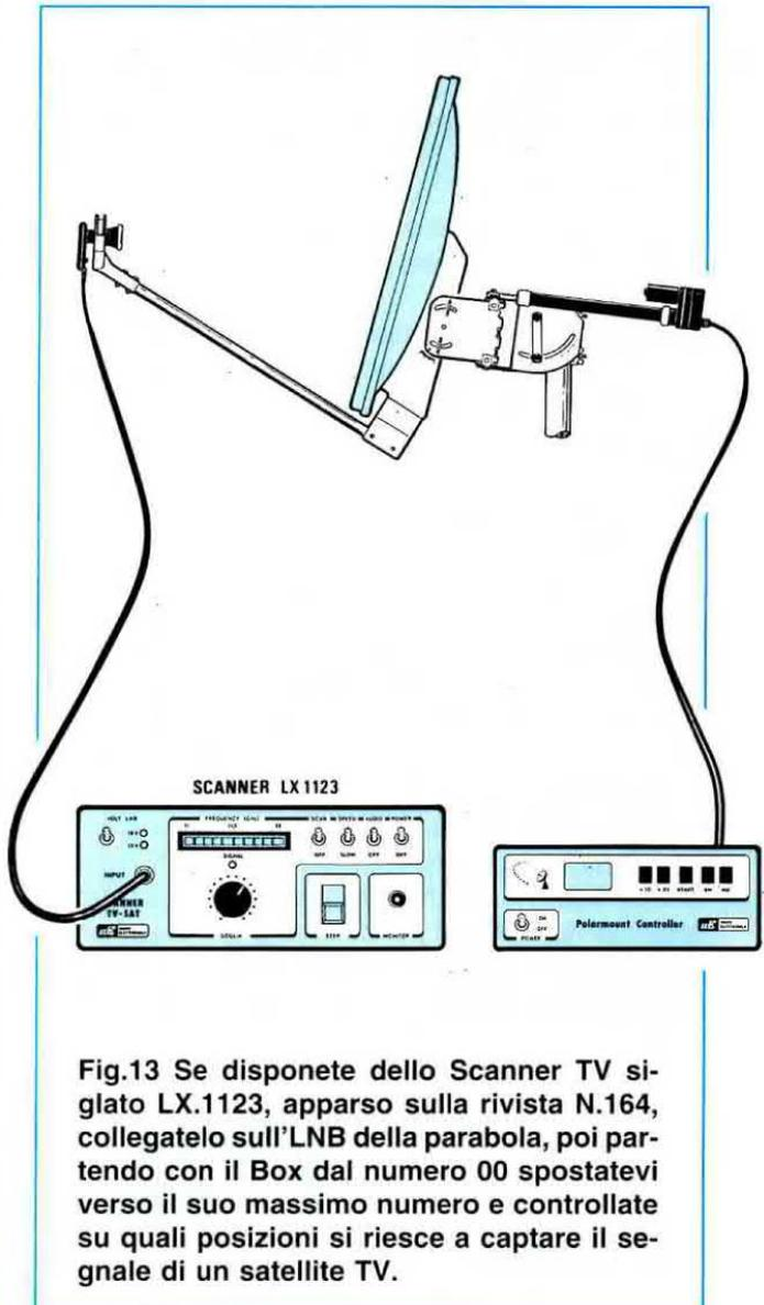
**Fig.13** Se disponete dello Scanner TV siglato LX.1123, apparso sulla rivista N.164, collegatelo sull'LNB della parabola, poi partendo con il Box dal numero 00 spostatevi verso il suo massimo numero e controllate su quali posizioni si riesce a captare il segnale di un satellite TV.
