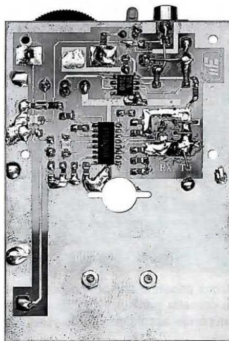
**Fig.15** Dal lato opposto trovate i due integrati e tutti gli altri componenti in SMD. Lo stampato fotografato è un prototipo che in seguito abbiamo leggermente modificato per la produzione di serie.
