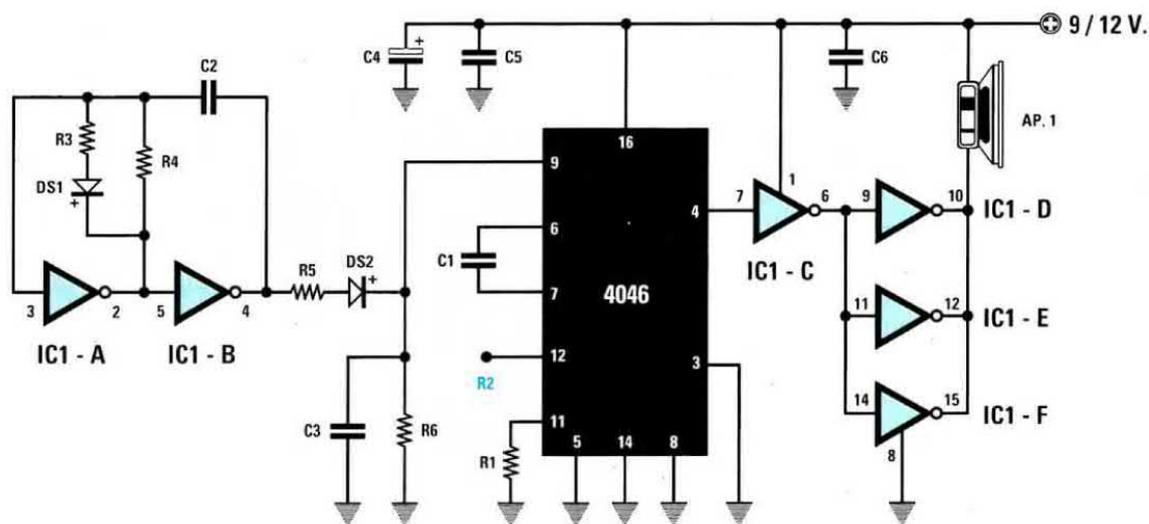
Fig.9 Schema elettrico di un generatore di suoni Spaziali. In questo schema non dovete collegare nessuna resistenza tra il piedino 12 dell'integrato 4046 e la massa. Per rendere il suono più o meno acuto è sufficiente modificare il valore della resistenza R1 portandolo dagli attuali 12.000 ohm a 15.000 o 10.000 ohm.
