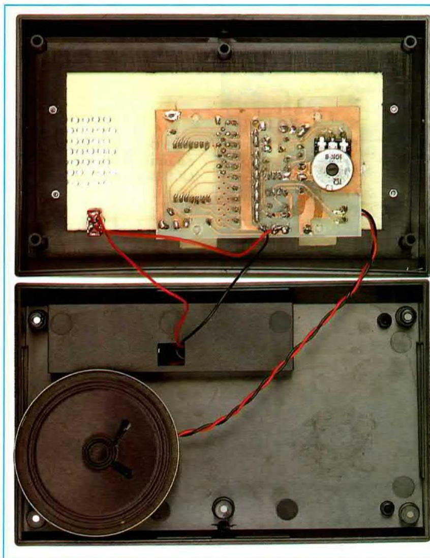
**Fig.7** Sul pannello frontale del mobile fissate lo stampato utilizzando i quattro distanziatori plastici inseriti nel kit. L'altoparlante verrà bloccato sul coperchio con una goccia di attacatutto.
