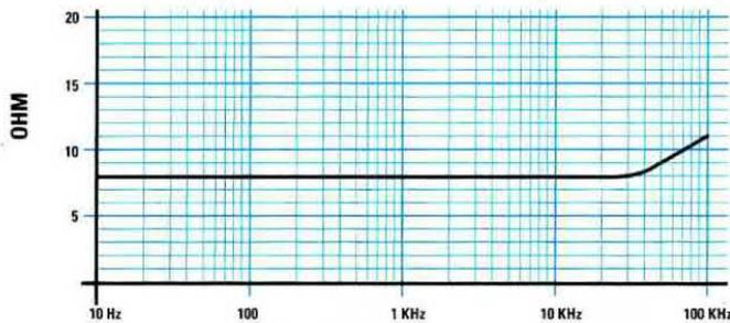
Fig.32 Se il diametro del filo ha una sezione adeguata ed i due fili risultano appaiati, noterete che il valore dell'impedenza rimane perfettamente lineare da 20 Hz fino a 30.000 Hz circa, cioè oltre il limite delle frequenze acustiche.
