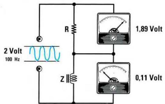
Fig.3 Se applichiamo ad R-Z una tensione "alternata" di 2 volt 100 Hz, ai capi della resistenza R rileveremo una tensione di 1,89 volt e ai capi dell'induttanza Z una tensione di 0,11 volt.
