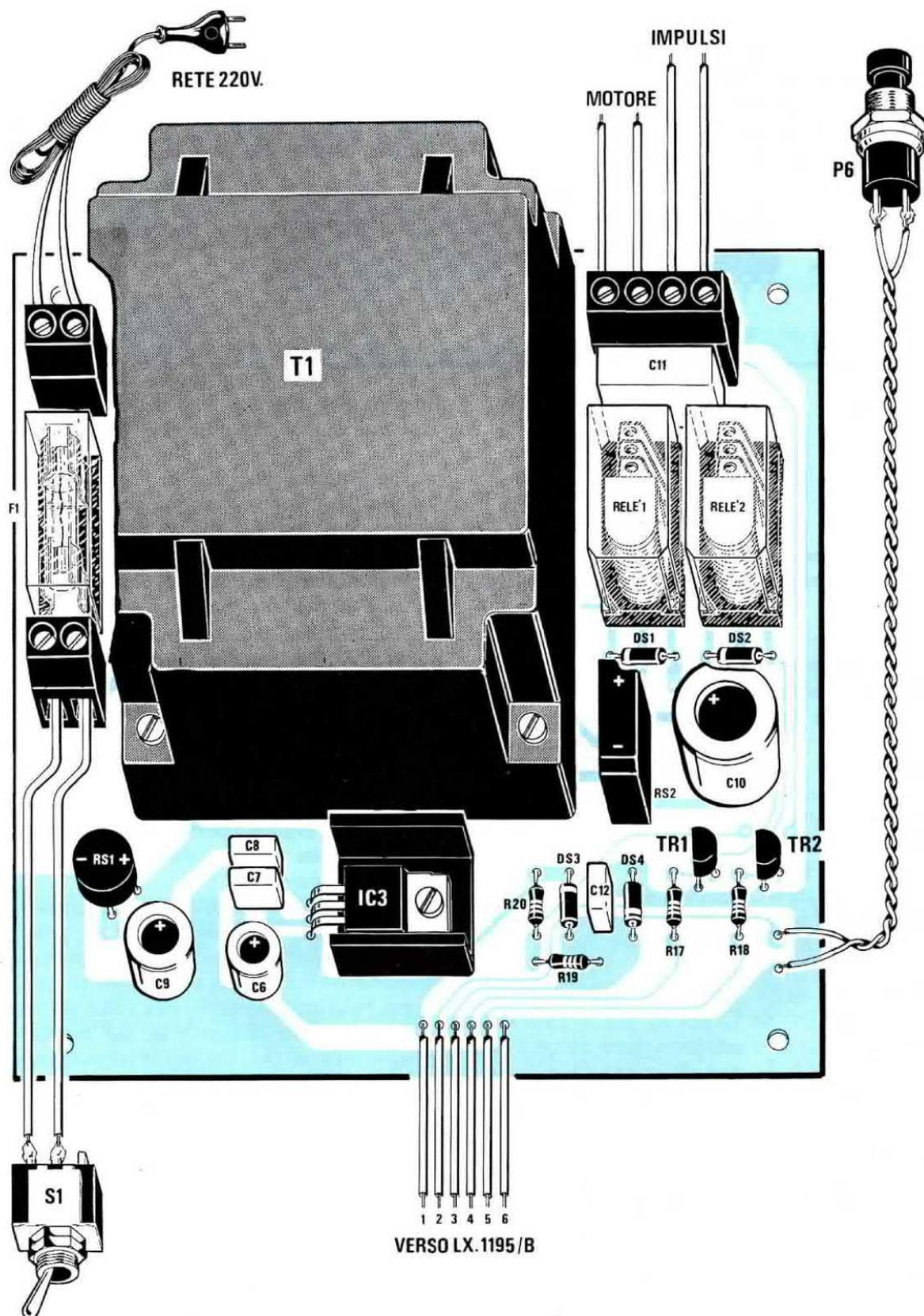
Fig.8 Schema pratico di montaggio del circuito base LX.1195. I fili visibili in basso, numerati da 1 a 6, andranno collegati al circuito stampato dei Display visibile in fig.9.
