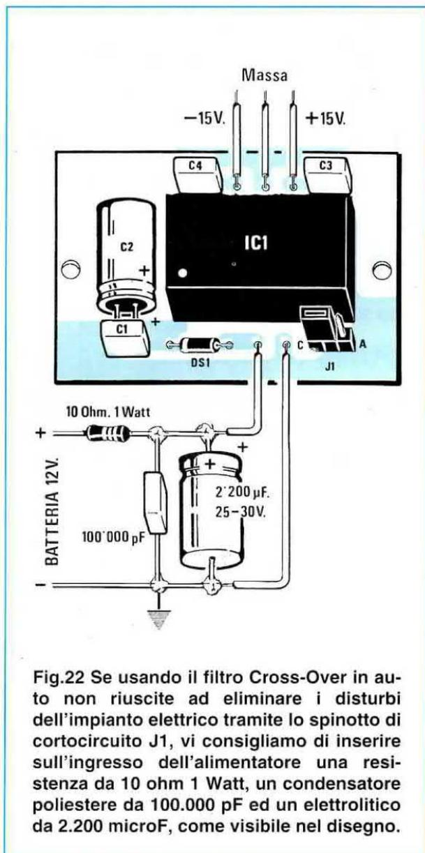
**Fig.22** Se usando il filtro Cross-Over in aiuto non riuscite ad eliminare i disturbi dell'impianto elettrico tramite lo spinotto di cortocircuito J1, vi consigliamo di inserire sull'ingresso dell'alimentatore una resistenza da 10 ohm 1 Watt, un condensatore poliestere da 100.000 pF ed un elettrolitico da 2.200 microF, come visibile nel disegno.
