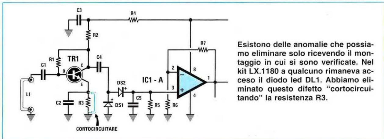
Esistono delle anomalie che possiamo eliminare solo ricevendo il montaggio in cui si sono verificate. Nel kit LX.1180 a qualcuno rimaneva acceso il diodo led DL1. Abbiamo eliminato questo difetto "cortocircuitando" la resistenza R3.
