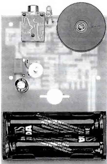
**Fig.14** Sul lato del circuito in cui inserirete le pile (cercando di non invertire la loro polarità) è presente un compensatore che non dovete ruotare, perché già tarato per ricevere la frequenza di 67,10 MHz.
