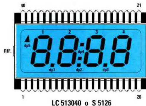
Fig.10 Il display LCD a 4 cifre utilizzato in questo progetto può risultare siglato LC.513040 oppure S.5126.
