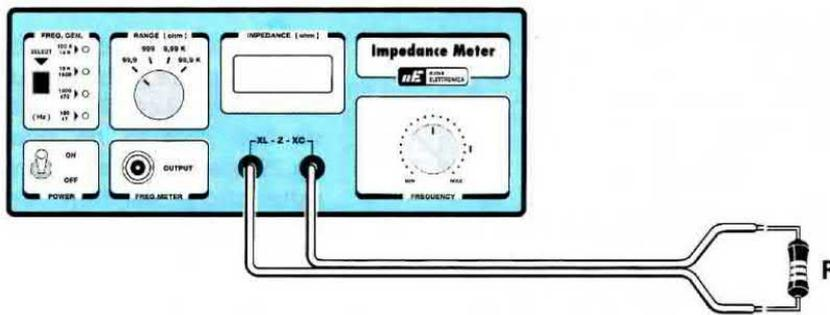
Fig.31 Per controllare se un cavo per Casse Acustiche può influenzare le frequenze Audio, collegatelo sull'ingresso dell'impedenzometro ed alla sua estremità applicate una resistenza che abbia un valore ohmico pari a quello delle Casse Acustiche.
