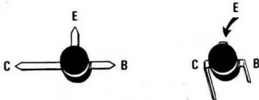
Fig.6 Il terminale più lungo del transistor BFR.96 è il Collettore. Quando ripiegate i suoi piedini ad L per poterlo inserire nei fori del circuito stampato (vedi fig.9), il terminale più lungo deve essere rivolto verso l'impedenza JAF6.
