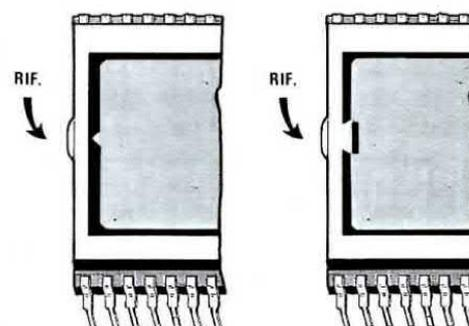
Fig.11 Per non inserire il display a rovescio, dovrete rivolgere la piccola sporgenza in vetro, utilizzata come riferimento, sulla sinistra (vedi fig.15).
