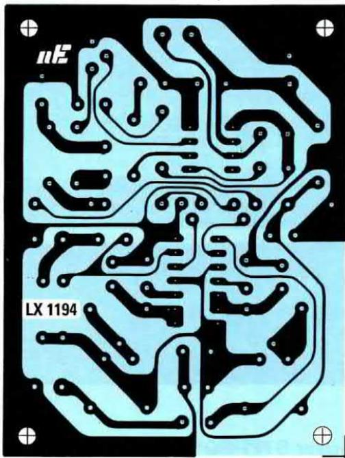
Fig.5 Disegno a grandezza naturale dello stampato LX.1194 visto dal lato rame. Questo circuito viene fornito già forato e completo di disegno serigrafico.
