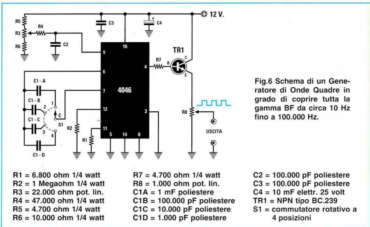
Fig.6 Schema di un Generatore di Onde Quadre in grado di coprire tutta la gamma BF da circa 10 Hz fino a 100.000 Hz.
