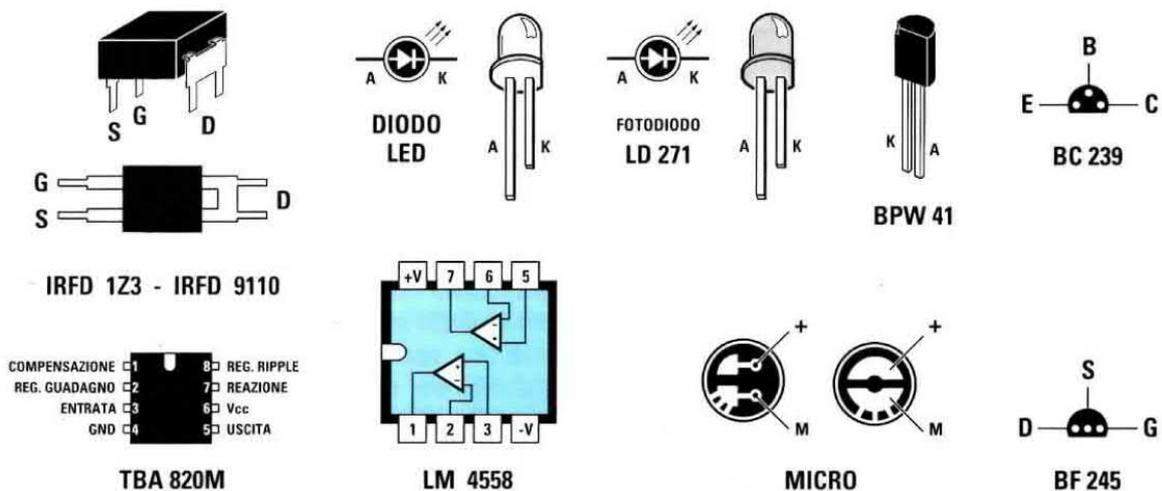
Fig.11 Connessioni di integrati, diodi, transistor e microfono preamplificato da utilizzare per la realizzazione dei due schemi riportati nelle figg.10-12.
