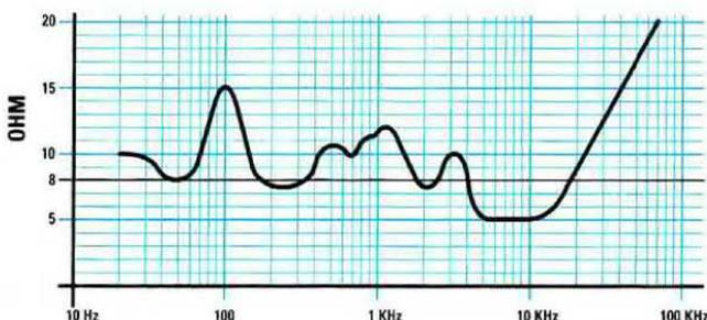
**Fig.27** Il grafico di una Cassa Acustica a 3 Vie alquanto scadente. Come potete notare la frequenza di risonanza del Woofer è sui 100 Hz anziché sui 30-40 Hz; abbassandosi notevolmente l'impedenza sulla gamma 3.000 - 15.000 Hz, lo stadio finale viene sovraccaricato.
