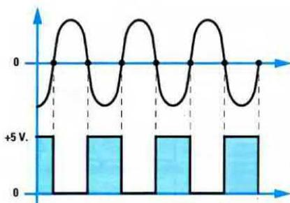
Fig.6 Quando la sinusoide della tensione alternata passa sullo "zero", sul Collettore del transistor TR1 (vedi schema elettrico di fig.8) ritroverete una tensione di 5 volt positivi.
