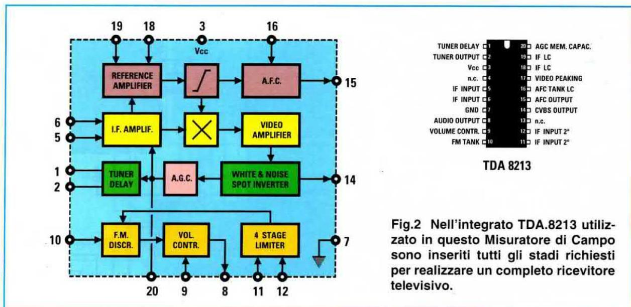
Fig.2 Nell'integrato TDA.8213 utilizzato in questo Misuratore di Campo sono inseriti tutti gli stadi richiesti per realizzare un completo ricevitore televisivo.
