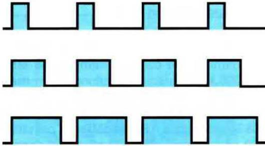
**Fig.2** Dal piedino 13 del 4046 fuoriusciranno degli impulsi ad onda quadra con un duty-cycle variabile. Queste onde quadre verranno convertite in una tensione continua dal "loop filter" (vedi R16-R17-C11-C12) e questa applicata ai diodi Varicap posti in parallelo alla bobina L1. Più si allargherà il tratto positivo rispetto al negativo, maggiore tensione giungerà sui diodi varicap della sintonia.
