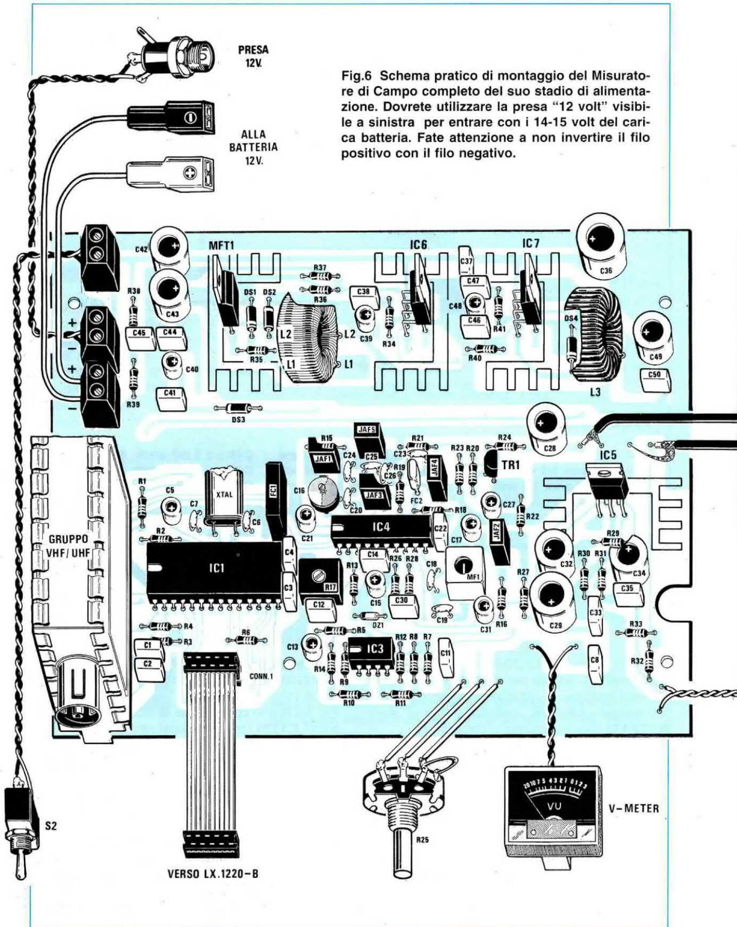
Fig.6 Schema pratico di montaggio del Misuratore di Campo completo del suo stadio di alimentazione. Dovrete utilizzare la presa "12 volt" visibile a sinistra per entrare con i 14-15 volt del carica batteria. Fate attenzione a non invertire il filo positivo con il filo negativo.
