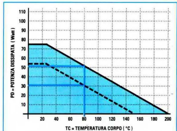
**Fig.7** Un transistor da 75 Watt con una  $T_J$  di 200 gradi dissiperà questa potenza soltanto se la temperatura del corpo non supera i 25 gradi. Se la temperatura del corpo dovesse raggiungere gli 80 gradi non potrete fargli dissipare più di 50 Watt. Per motivi di sicurezza converrà non superare i 30 Watt (vedi linea diagonale tratteggiata).
