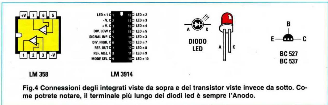
Fig.4 Connessioni degli integrati viste da sopra e dei transistor viste invece da sotto. Come potrete notare, il terminale più lungo dei diodi led è sempre l'Anodo.
