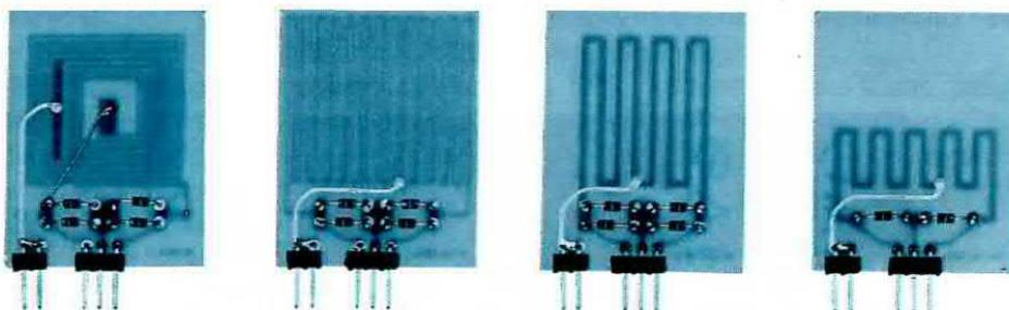
Fig.7 Anche se nel kit troverete 4 circuiti stampati ed i connettori per le quattro bobine, **NON TROVERETE 14 diodi Varicap**, ma soltanto 4. Chi volesse più diodi varicap BB.909 potrà richiederli a parte quando ordinerà il kit. Come potete vedere in questa foto e nella fig.6, sulla bobina da 138-164 MHz andranno applicati 2 soli diodi Varicap.
