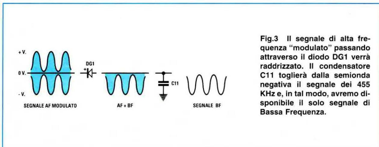
**Fig.3** Il segnale di alta frequenza "modulato" passando attraverso il diodo DG1 verrà raddrizzato. Il condensatore C11 toglierà dalla semionda negativa il segnale dei 455 KHz e, in tal modo, avremo disponibile il solo segnale di Bassa Frequenza.
