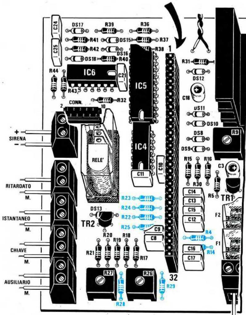
Fig.4 Innestando questa nuova scheda LX.1084/C sulla scheda base, dovrete necessariamente sostituire tutte le resistenze che nel disegno abbiamo colorato in BLU (nello schema precedente erano da 47.000 ohm) con altre da 1.000 ohm (vedi elenco sottoriportato).
