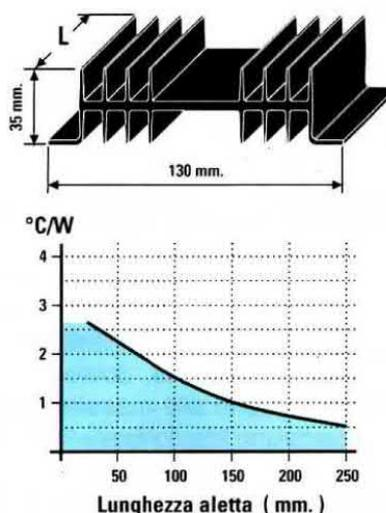
Fig.14 Il valore della resistenza termica in  $^{\circ}\text{C/W}$  di un'aletta di raffreddamento dipende dalla forma del suo profilato e dalla sua lunghezza. Uno spezzone lungo 50 mm ha circa 2,25  $^{\circ}\text{C/W}$  ed uno spezzone lungo 200 mm ha circa 0,75  $^{\circ}\text{C/W}$ .
