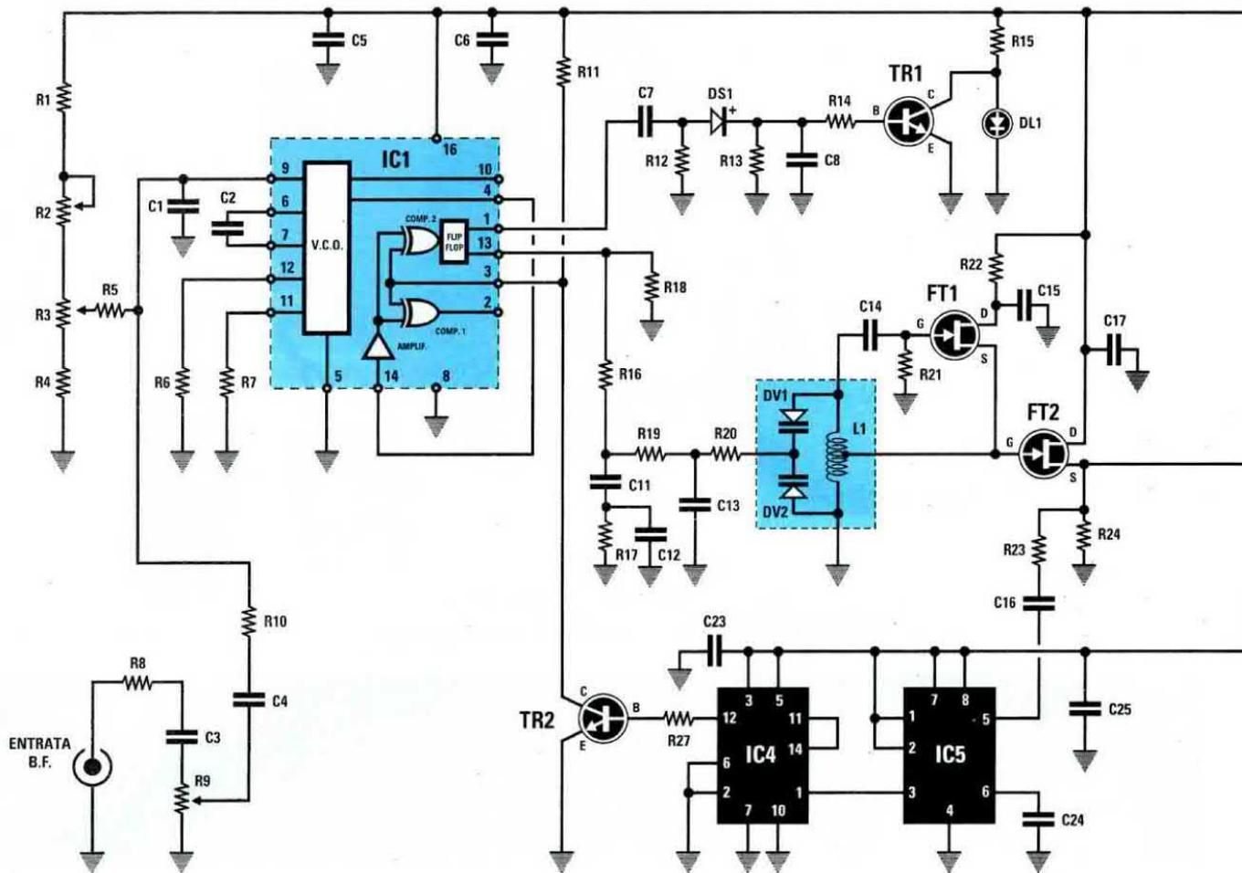
Fig.1 Schema elettrico del VFO in grado di superare anche i 170 MHz. Per variare la frequenza dovreste agire sul potenziometro R2 o sul trimmer R3. Entrando con un segnale di Bassa Frequenza nella presa "entrata BF" potrete modulare il VFO in FM.
