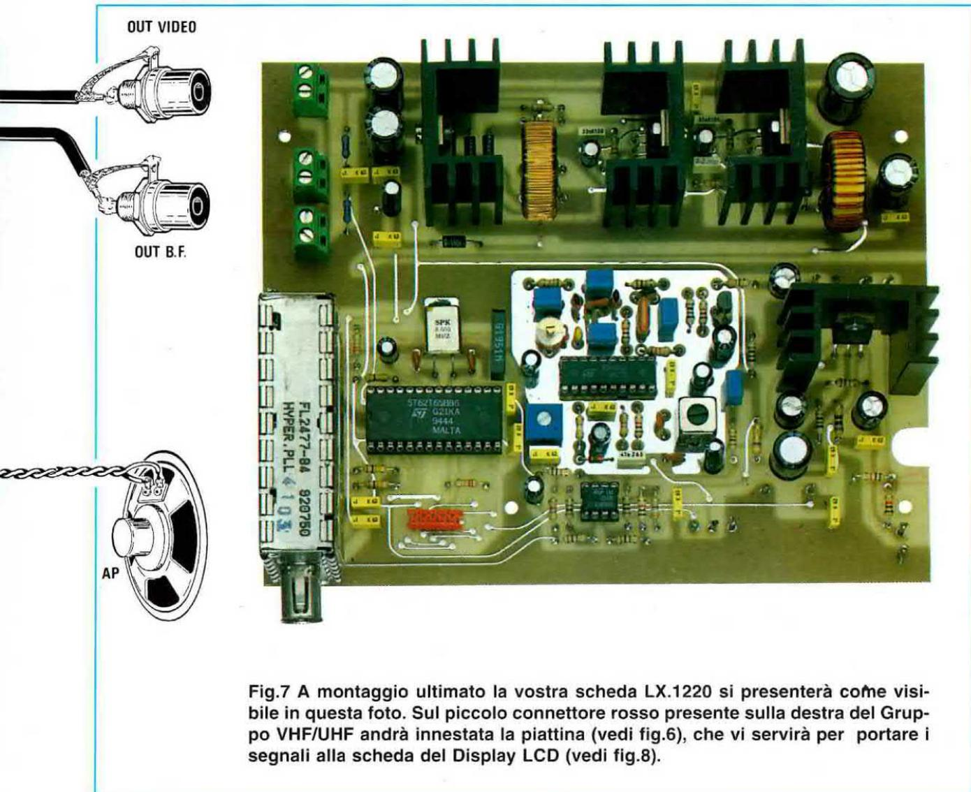
Fig.7 A montaggio ultimato la vostra scheda LX.1220 si presenterà come visibile in questa foto. Sul piccolo connettore rosso presente sulla destra del Gruppo VHF/UHF andrà innestata la piattina (vedi fig.6), che vi servirà per portare i segnali alla scheda del Display LCD (vedi fig.8).
