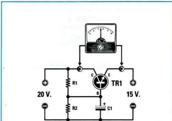
**Fig.10** Per conoscere la potenza in Watt che dissiperà in "calore" un transistor finale di uno stadio alimentatore, dovrete sottrarre al valore della tensione applicata sull'ingresso, il valore della tensione che preleverete in uscita e moltiplicare la differenza per gli Amper che dovrà erogare.
