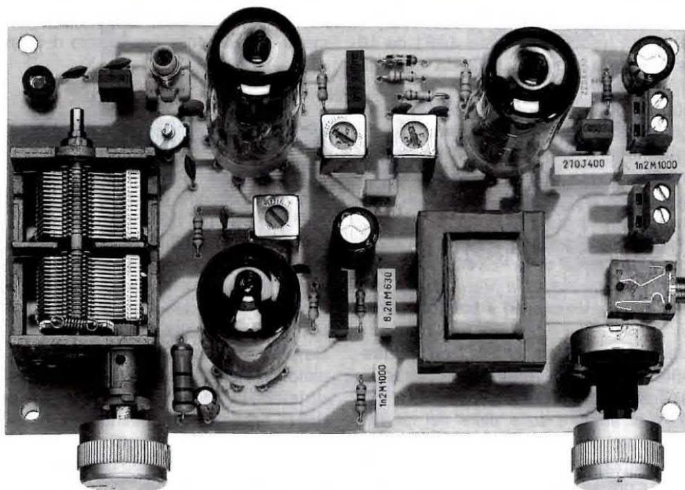
**Fig.9** Ecco come si presenterà a montaggio ultimato questa semplice supereterodina valvolare per Onde Corte. Perchè funzioni correttamente occorre utilizzare come antenna un filo lungo 8-9 metri possibilmente steso all'esterno della casa. Se utilizzerete una cuffia migliore rispetto a quella di tipo standard che troverete inserita nel kit, riuscirete ad aumentare il livello sonoro.
