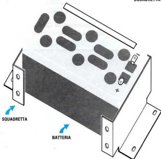
Fig.14 La squadretta di fissaggio andrà fissata sia sul pannello posteriore con 4 viti, sia sulla base del mobile con delle viti autofilettanti. Per ottenere una base stabile per la batteria, dovrete asportare con una tronchesina le due sporgenze in plastica presenti sulla base del mobile e sotto il centro della batteria.
