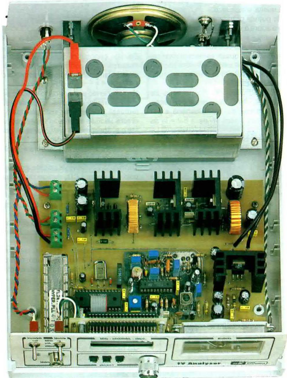
**Fig.12** In questa foto potete vedere la posizione in cui andrà fissato il circuito stampato Base del Misuratore di Campo e la sua batteria di alimentazione. La fascetta di fissaggio della batteria servirà anche per bloccare l'altoparlante sul pannello posteriore (vedi fig.13). Prima di fissare il circuito stampato Base, dovrete già aver applicato sul pannello anteriore la scheda del display e lo strumentino V-Meter, utilizzando per quest'ultimo un sottile ritaglio di alluminio.
