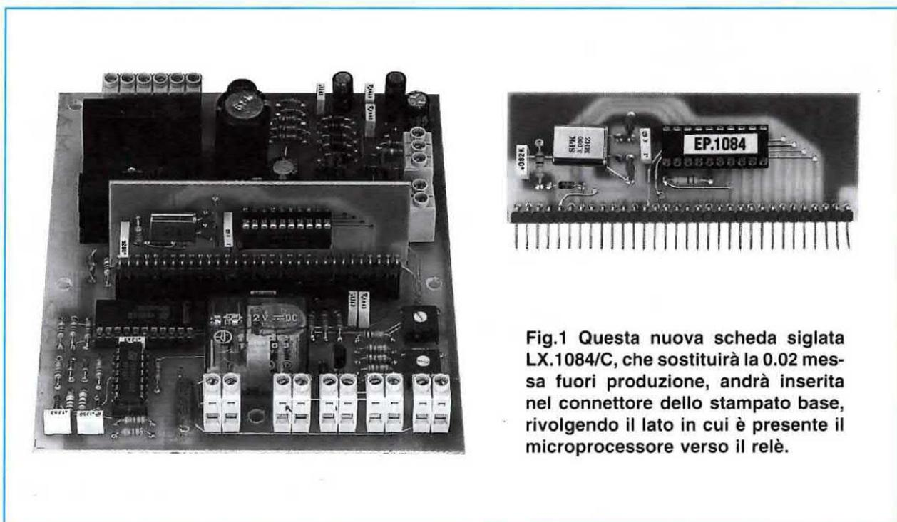
Fig.1 Questa nuova scheda siglata LX.1084/C, che sostituirà la 0.02 messa fuori produzione, andrà inserita nel connettore dello stampato base, rivolgendo il lato in cui è presente il microprocessore verso il relè.
