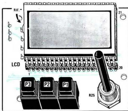
Fig.11 Anche sul corpo del display è presente un "riferimento" che dovreste rispettare. Questo riferimento è costituito da una minuscola goccia di stagno posta sul lato sinistro o dal segno "<" posto nella sottile cornice interna del display.
