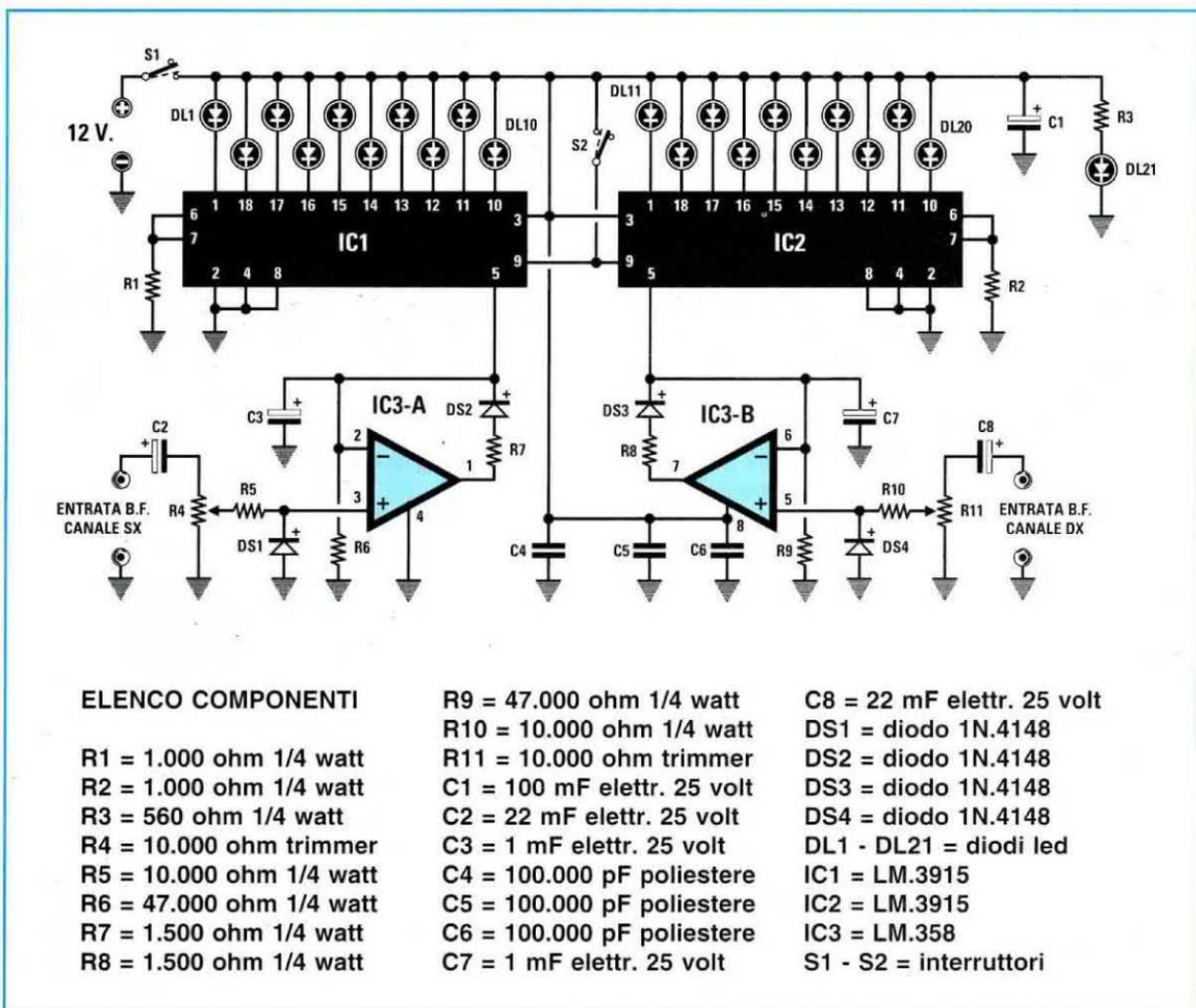
di alimentazione e di accendere un **solo diodo** che si muoverà da sinistra verso destra a tempo di musica a seconda dell'ampiezza del segnale, quando verrà tolta da questi piedini la tensione dei 12 volt. Per **tarare** questo circuito è sufficiente alzare il **volume** della radio per il suo massimo e tarare i trimmer **R4** ed **R11** fino ad accendere tutti e **10** i diodi led.
