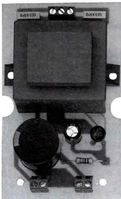
Fig.8 Questo stadio di alimentazione potrà servirvi per alimentare delle altre piccole apparecchiature a valvola che pubblicheremo nella rivista in futuro.
