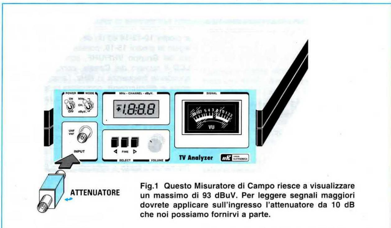
Fig.1 Questo Misuratore di Campo riesce a visualizzare un massimo di 93 dBuV. Per leggere segnali maggiori dovrete applicare sull'ingresso l'attenuatore da 10 dB che noi possiamo fornirvi a parte.
