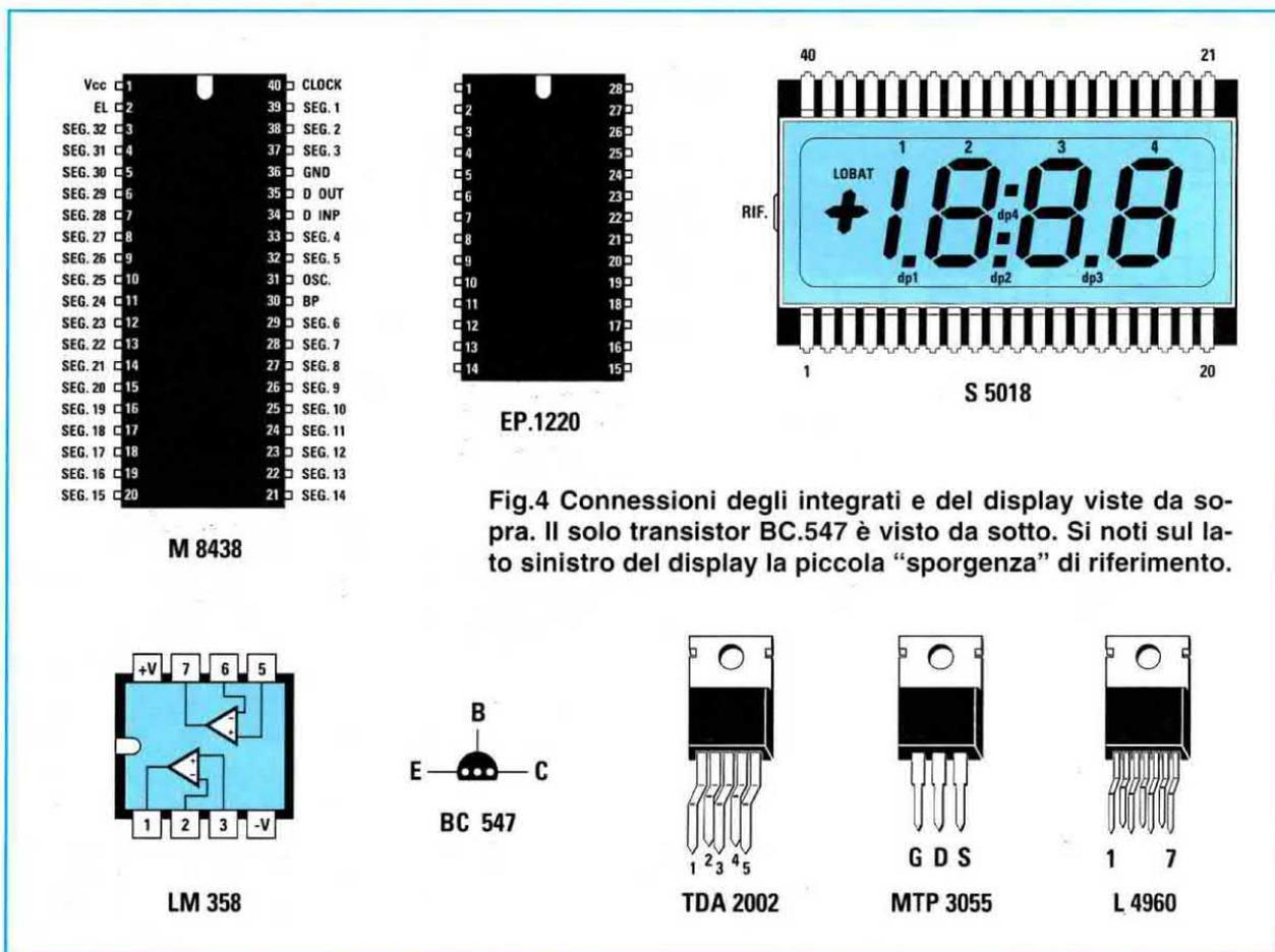
Fig.4 Connessioni degli integrati e del display viste da sopra. Il solo transistor BC.547 è visto da sotto. Si noti sul lato sinistro del display la piccola "sporgenza" di riferimento.
