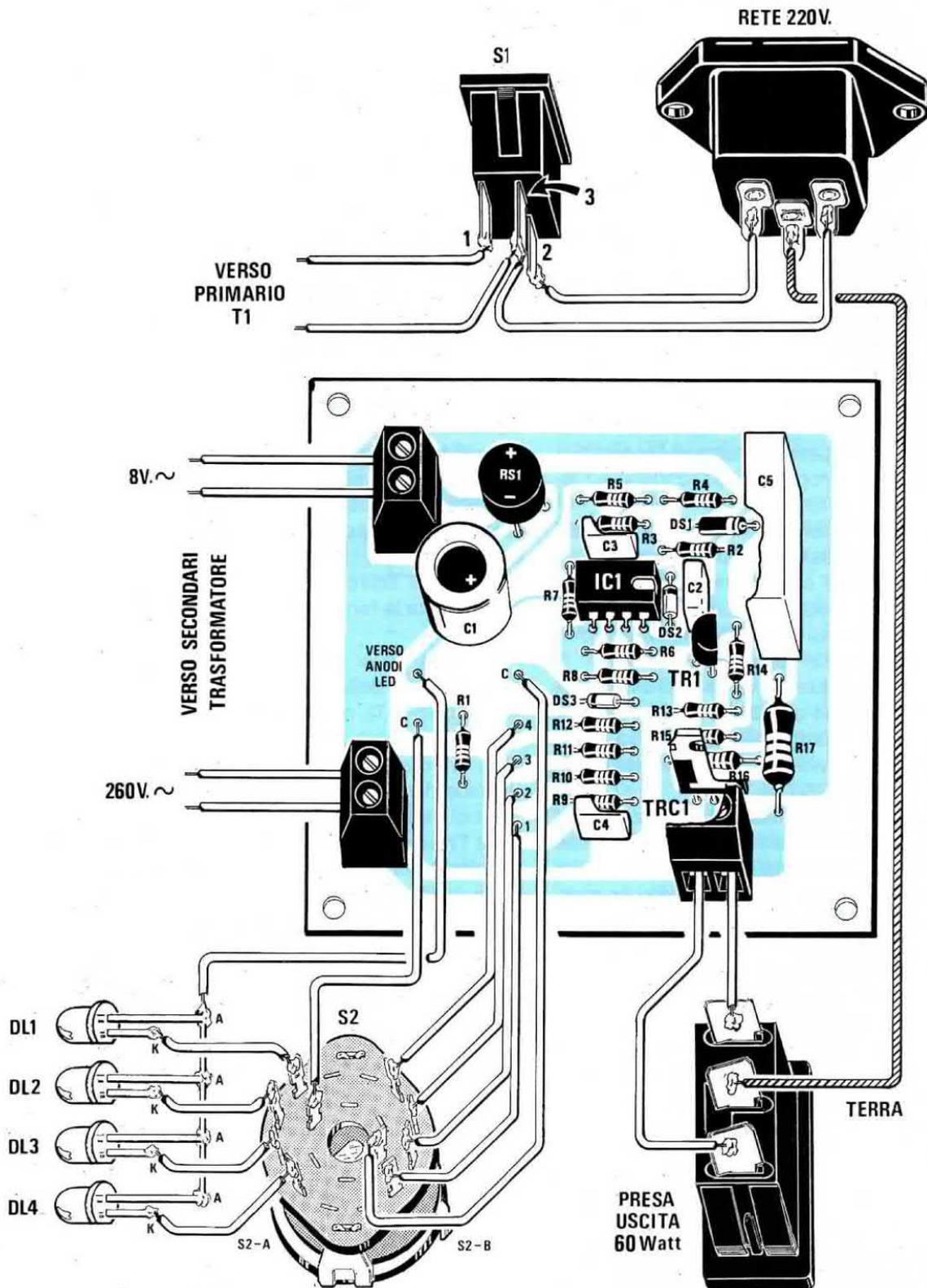
Fig.3 Schema pratico di montaggio dell'alimentatore descritto nell'articolo. Controllate attentamente le connessioni del commutatore S2 ed il colore dei fili da inserire nel morsettiere dei 260 volt (fili rossi) e degli 8 volt (fili bianchi). Il filo centrale che collega la presa d'ingresso dei 220 volt con quella di uscita è quello di Terra.
