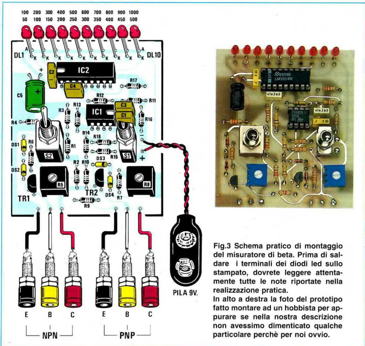
Fig.3 Schema pratico di montaggio del misuratore di beta. Prima di saldare i terminali dei diodi led sullo stampato, dovrete leggere attentamente tutte le note riportate nella realizzazione pratica.
