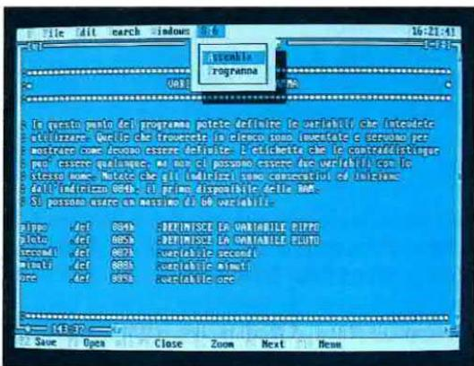
Fig.6 Corretto o riscritto, dovrete "salvare" il nuovo programma premendo il tasto **F2**, dopodichè lo potrete **ASSEMBLARE** premendo i tasti **ALT T** poi **A**. Se non avete commesso "errori" apparirà **SUCCESS**.
