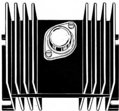
Fig.16 Se il transistor viene applicato sull'estremità di un'aletta di raffreddamento, questa preleverà meno calore dal corpo del transistor, quindi si riscalderà di meno ed il transistor molto di più. In pratica si otterrà lo stesso risultato che si avrebbe utilizzando un'aletta di dimensioni minori.
