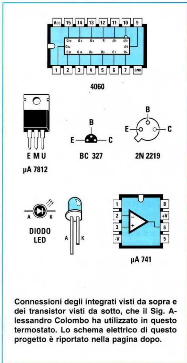
Connessioni degli integrati visti da sopra e dei transistor visti da sotto, che il Sig. Alessandro Colombo ha utilizzato in questo termostato. Lo schema elettrico di questo progetto è riportato nella pagina dopo.
