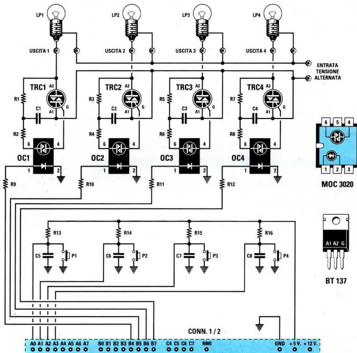
Fig.7 Schema elettrico della scheda Triac siglata LX.1206 e connessioni del fototriac visto da sopra e del triac BT.137. Sulle "uscite" dei Triac dovreste collegare delle lampadine o altre apparecchiature elettriche che funzionino con il valore della tensione alternata che applicherete sulla morsetteria d'ingresso (vedi fig.8).
