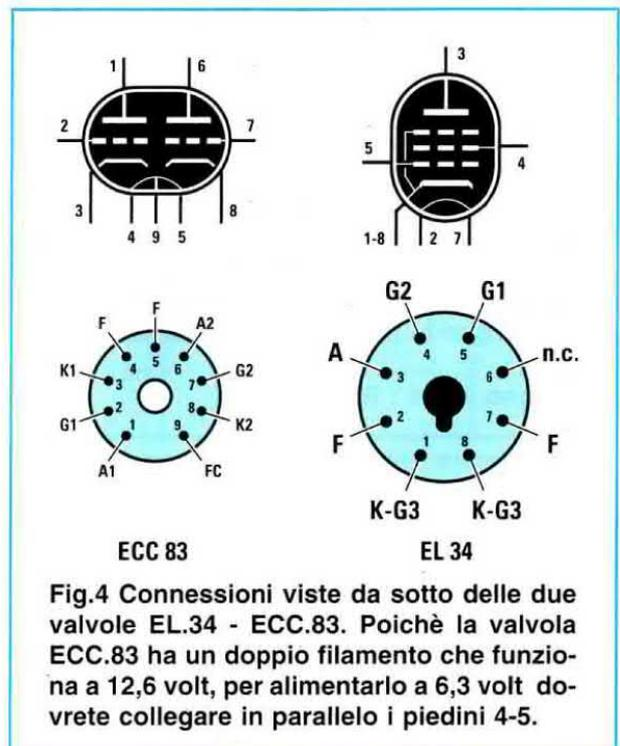
Fig.4 Connessioni viste da sotto delle due valvole EL.34 - ECC.83. Poichè la valvola ECC.83 ha un doppio filamento che funziona a 12,6 volt, per alimentarlo a 6,3 volt dovrete collegare in parallelo i piedini 4-5.
