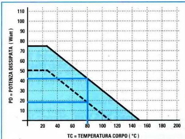
**Fig.8** Un transistor da 75 Watt con una TJ di 150 gradi dissiperà questa potenza soltanto se la temperatura del corpo non supera i 25 gradi. Se la temperatura del corpo dovesse raggiungere gli 80 gradi, non potrete fargli dissipare più di 42 Watt. Per motivi di sicurezza converrà non superare i 20 Watt (vedi linea diagonale tratteggiata).
