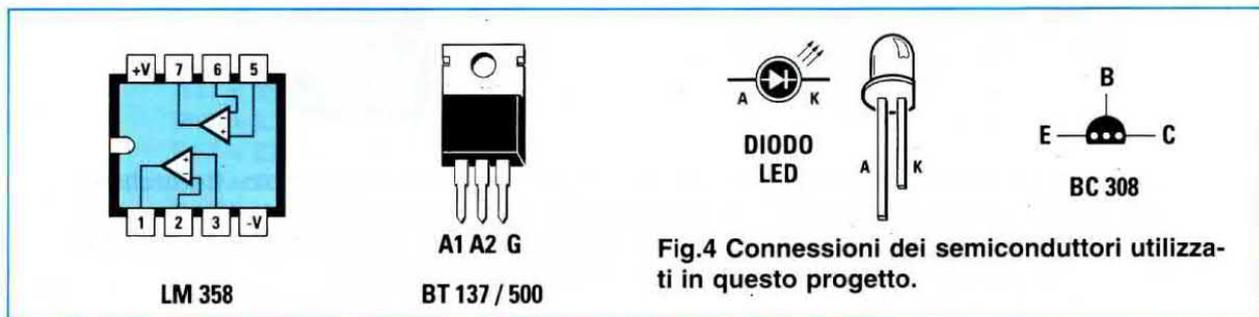
Fig.4 Connessioni dei semiconduttori utilizzati in questo progetto.
