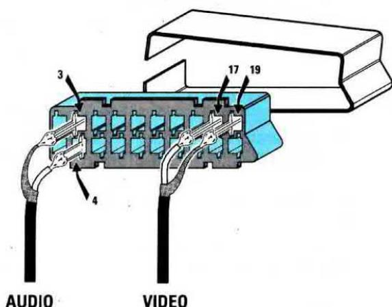
**Fig.17** Se collegherete le due prese d'uscita "Out Video - Out BF" (vedi fig.6) all'ingresso di un monitor TV a colori, potrete vedere sullo schermo le immagini delle emittenti che capterete. Se avete un monitor o TV provvisto di una presa SCART, potrete collegare l'Audio ai terminali 3-4 ed il Video ai terminali 17-19. Ricordatevi di collegare la calza di schermo ai terminali 3-19.
