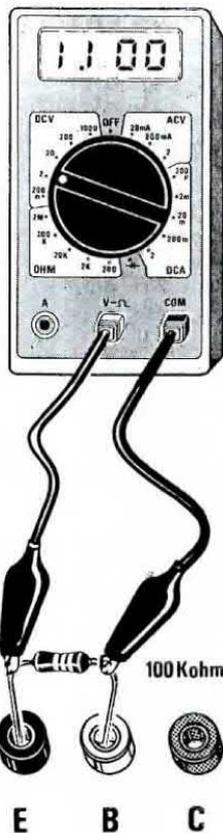
Fig.5 Per la taratura potrete commutare il tester digitale sulla posizione 200 microA. CC, poi applicare i due puntali sulle boccole E-B dell'NPN (vedi figura di sinistra), tarare il trimmer R5 fino a leggere 11 microAmper, quindi inserire i puntali nelle boccole E-B del PNP e tarare il trimmer R8.
