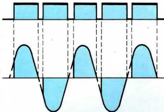
**Fig.5** Se il Triac viene eccitato ogniqualvolta la sinusoide passa sullo 0, in uscita si otterrà la "massima" tensione di alimentazione. Se viene eccitato in ritardo, si otterrà una tensione minore.
