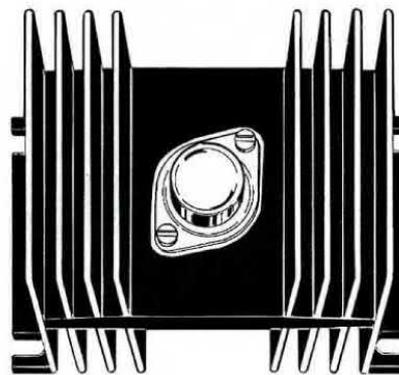
Fig.17 Per prelevare dal corpo del transistor una maggior quantità di calore, dovrete sempre collocarlo al centro dell'aletta. Il calore, equamente distribuito sulla superficie totale, verrà così irradiato più velocemente verso l'ambiente esterno e la temperatura del transistor scenderà di molti gradi.
