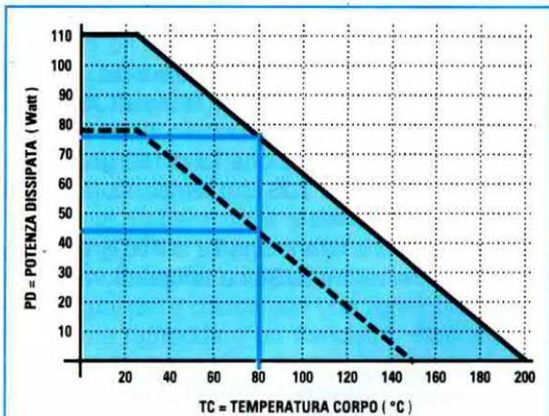
**Fig.6** Un transistor da 110 Watt con una  $T_J$  di 200 gradi dissiperà questa potenza soltanto se la temperatura del corpo non supera i 25 gradi. Se la temperatura del corpo dovesse raggiungere gli 80 gradi, non potrete fargli dissipare più di 75 Watt. Per motivi di sicurezza converrà non superare i 45 Watt (vedi linea diagonale tratteggiata).
