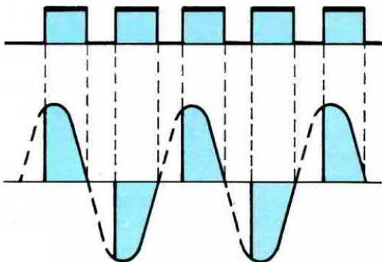
**Fig.6** Più aumenterà il ritardo di eccitazione del Triac rispetto al passaggio sullo 0 della sinusoide, meno tensione preleverete sulla sua uscita, e da 260 volt potrete scendere anche a soli 100 volt.
