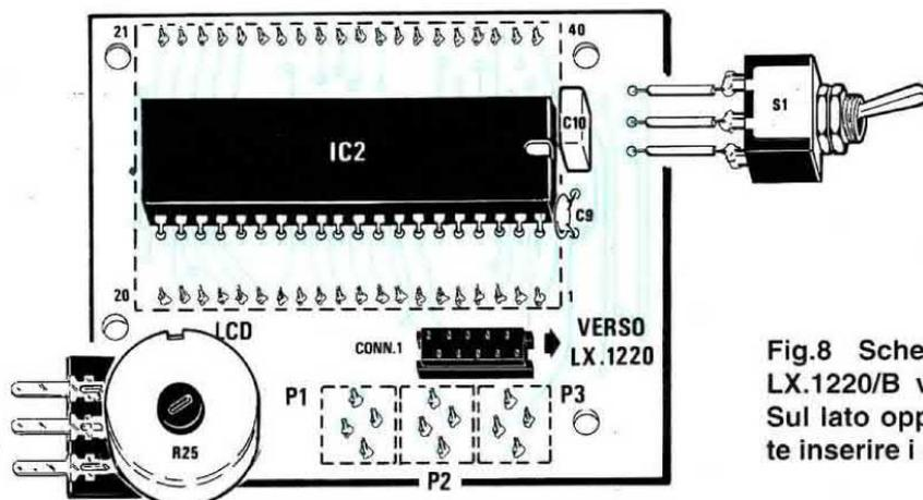
Fig.8 Schema pratico della scheda LX.1220/B vista dal lato dell'integrato. Sul lato opposto dello stampato dovreste inserire i componenti visibili in fig.11.
