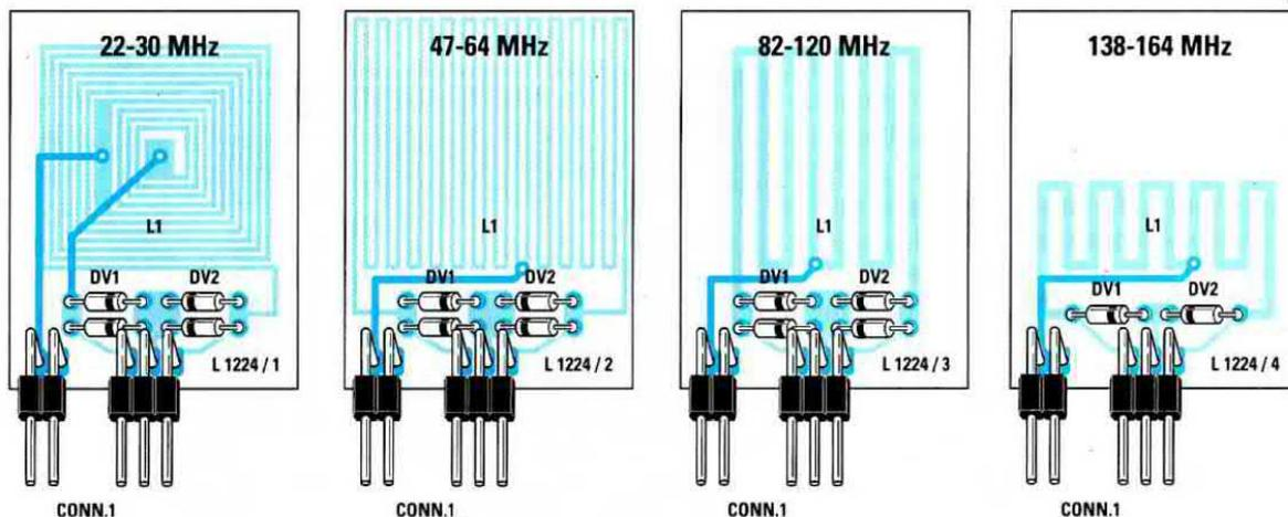
Fig.6 Nel kit troverete quattro circuiti stampati con le bobine già incise in grado di coprire le gamme che troverete indicate sul loro corpo. In queste bobine dovrete inserire i diodi varicap, cercando di non invertirne la polarità e i due connettori maschi a 2 e 3 terminali.
