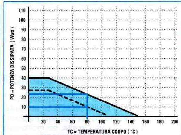
**Fig.9** Un transistor da 40 Watt con una TJ di 150 gradi dissiperà questa potenza soltanto se la temperatura del corpo non supera i 25 gradi. Se la temperatura del corpo dovesse raggiungere gli 80 gradi, non potrete fargli dissipare più di 26 Watt. Per motivi di sicurezza converrà non superare i 10 Watt (vedi linea diagonale tratteggiata).
