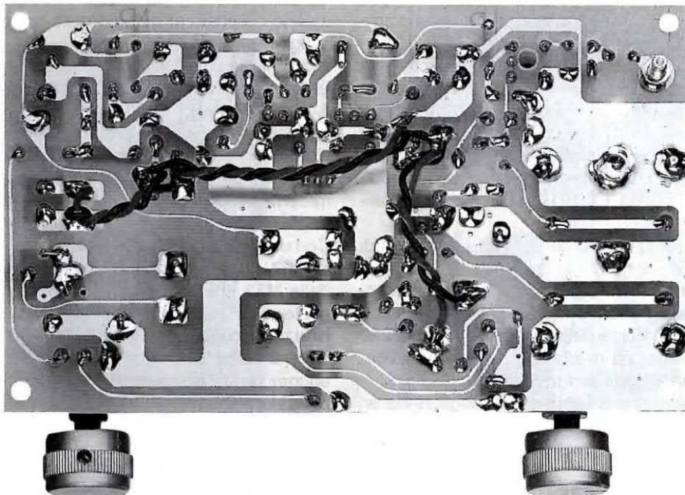
**Fig.10** Il circuito stampato che vi forniamo già inciso e forato, semplificherà al massimo la realizzazione pratica di questa supereterodina valvolare. In questa foto sono visibili i due fili utilizzati per portare la tensione dei 6,3 volt ai filamenti. Consigliamo di applicare questo circuito su una tavoletta di legno per evitare di lasciare scoperte le piste in rame percorse dalla tensione continua di 150 volt.
