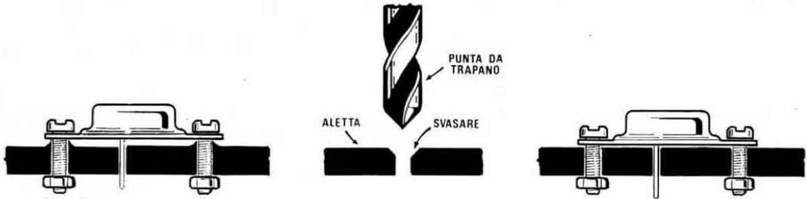
**Fig.15** Prima di fissare un transistor su un'aletta di raffreddamento consigliamo di controllare se la sua superficie risulta perfettamente piana. Se notate che i bordi dei fori risultano leggermente sporgenti, li dovrete svasare con una punta da trapano. Se tali imperfezioni non verranno eliminate, il corpo del transistor non riuscendo ad aderire perfettamente sul metallo dell'aletta di raffreddamento, si "brucerà" dopo pochi minuti.
