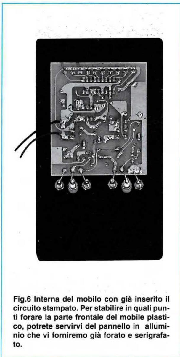
**Fig.6** Interna del mobile con già inserito il circuito stampato. Per stabilire in quali punti forare la parte frontale del mobile plastico, potrete servirvi del pannello in alluminio che vi forniremo già forato e serigrafato.
