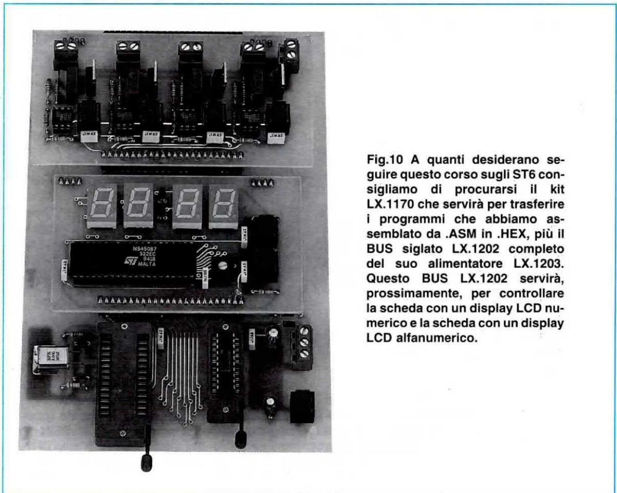
**Fig.10** A quanti desiderano seguire questo corso sugli ST6 consigliamo di procurarsi il kit LX.1170 che servirà per trasferire i programmi che abbiamo assemblato da .ASM in .HEX, più il BUS siglato LX.1202 completo del suo alimentatore LX.1203. Questo BUS LX.1202 servirà, prossimamente, per controllare la scheda con un display LCD numerico e la scheda con un display LCD alfanumerico.
