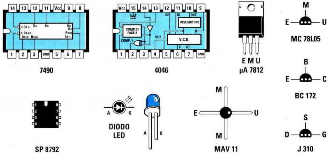
Fig.9 Connessioni degli integrati SN.7490 - CD.4046 - SP.8792 viste da sopra. Le connessioni di tutti gli altri componenti MC.78L05 - BC.172 - J.310 sono viste da sotto. Quando inserirete nello stampato l'amplificatore a larga banda MAV.11 ricordatevi che il terminale USCITA è quello posto vicino al "punto di riferimento" stampigliato sul corpo plastico.
