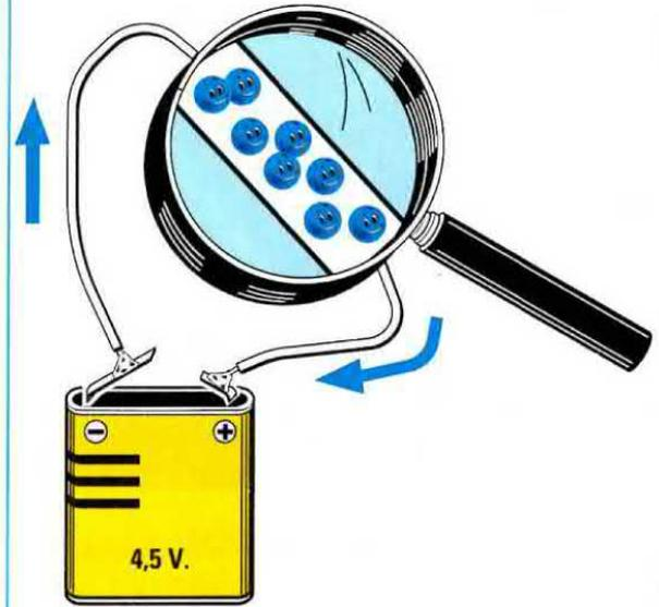
Fig.10 Gli Elettroni vengono attirati dai Protoni quindi il flusso della corrente elettrica va dal negativo verso il positivo.
