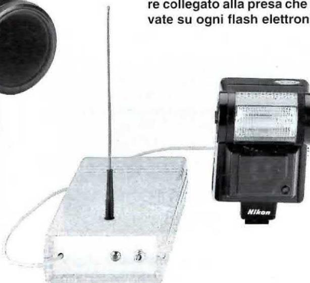
**Fig.2** Il cavetto schermato che esce dal ricevitore deve essere collegato alla presa che trovate su ogni flash elettronico.
