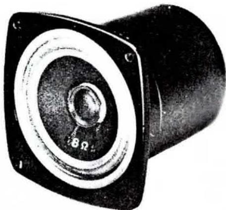
Fig.14 Se volete usare un altoparlante a larga banda come Midrange, dovrete proteggere il suo cono racchiudendo l'altoparlante dentro una piccola cassetta quadrata in legno oppure in metallo.
