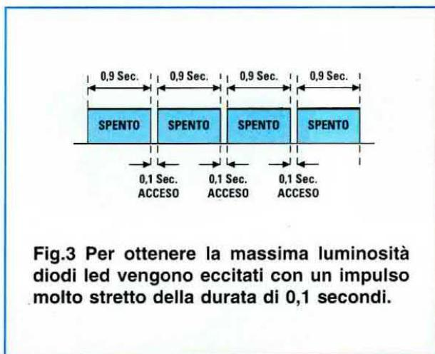
Non è consigliabile aumentare questo tempo sostituendo la resistenza **R2** con una di maggiore valore, ad esempio di **15.000 ohm**, perché si potrebbero danneggiare i tre diodi led.
