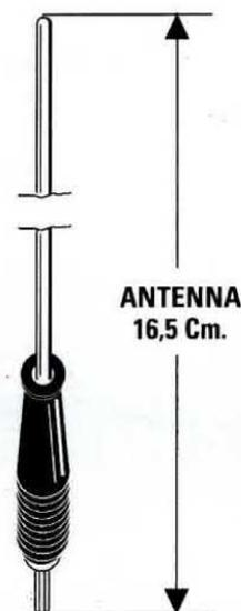
**Fig.18** L'antenna da usare per il trasmettitore e per i ricevitori è costituita da uno spezzone di filo di rame "nudo" che va fissato dentro la spina maschio inserita nel kit. La lunghezza totale del filo, incluso lo spinotto della banana, deve essere compresa tra i 16,5 e i 17 centimetri.
