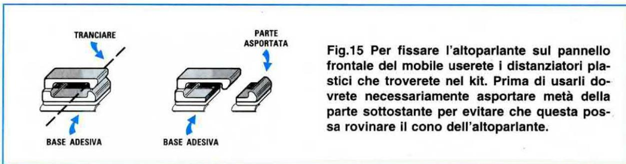
**Fig.15** Per fissare l'altoparlante sul pannello frontale del mobile userete i distanziatori plastici che troverete nel kit. Prima di usarli dovrete necessariamente asportare metà della parte sottostante per evitare che questa possa rovinare il cono dell'altoparlante.
