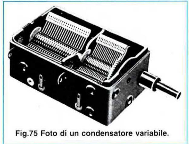
Fig.75 Foto di un condensatore variabile.
