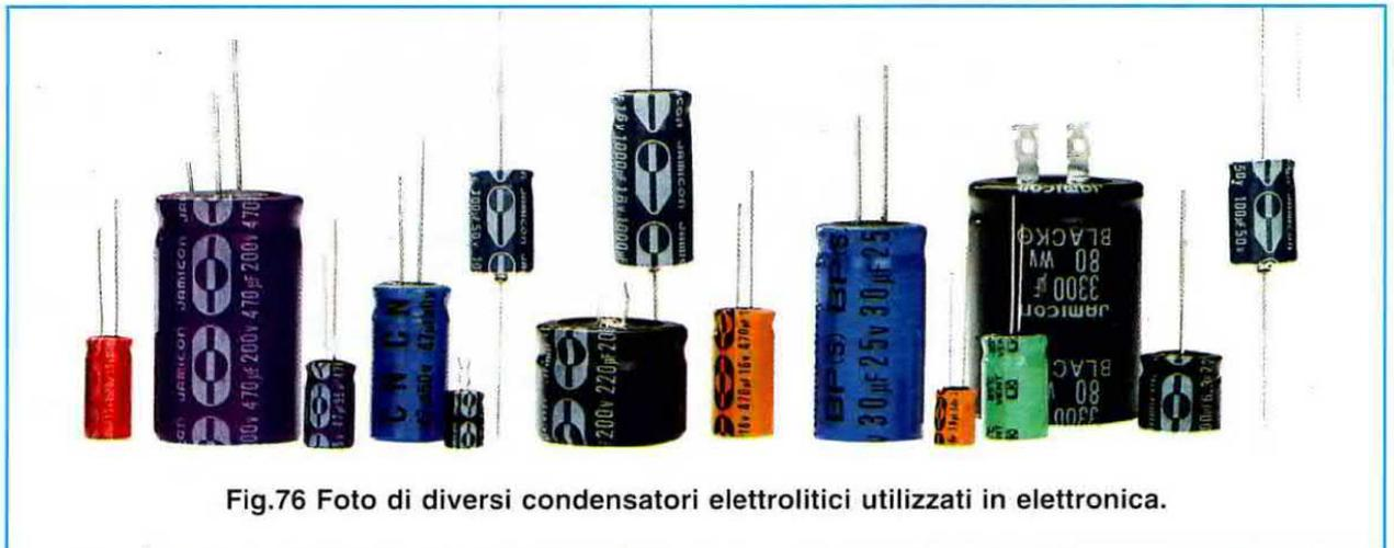
Fig.76 Foto di diversi condensatori elettrolitici utilizzati in elettronica.
