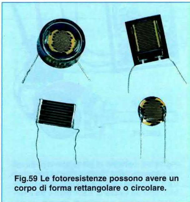
Fig.59 Le fotoresistenze possono avere un corpo di forma rettangolare o circolare.
