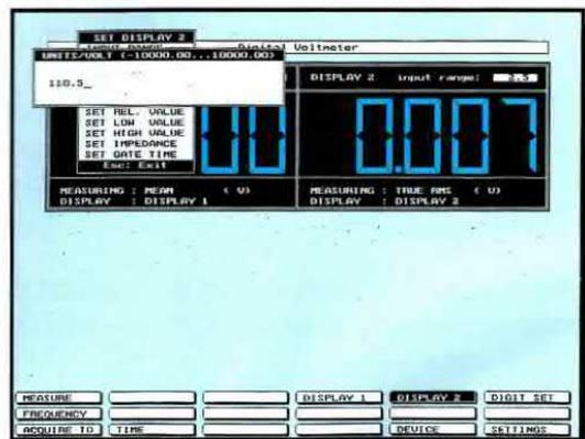
Fig.36 Nella finestra che appare andate sulla riga UNITS/VOLT e pigiate Enter e nella finestra scrivete i gradi che si ottengono quando la sonda fornisce 1 volt.
