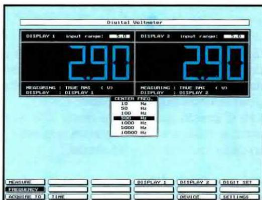
Fig.19 Per leggere con precisione un valore di tensione nelle misure volt AC dovrete andare su Frequency ed indicare il centro frequenza (leggere articolo).
