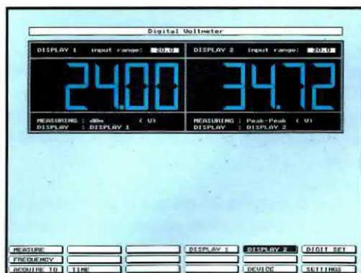
Fig.27 Sul primo display appare scritto il valore in dBm e sul secondo display il valore della tensione RMS oppure, se preferite, in volt Peak-Peak.
