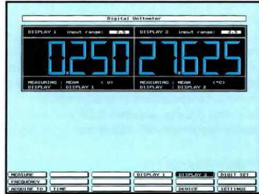
Fig.37 Pigiando Enter in fig.7 visualizzate sul Display 1 la tensione fornita dalla sonda e sul Display 2 il corrispondente valore in GRADI centigradi.
