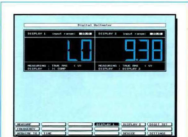
Fig.40 Se nel SET VALUE avete inserito un valore di minima e di massima, sul Display 1 vedrete apparire HIGH se è maggiore, LO se minore oppure PASS.
