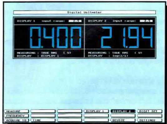
Fig.42 Sul primo display appariranno i volt d'ingresso e sul secondo il Guadagno in dB. Potete usare questa funzione anche per calcolare una Attenuazione.
