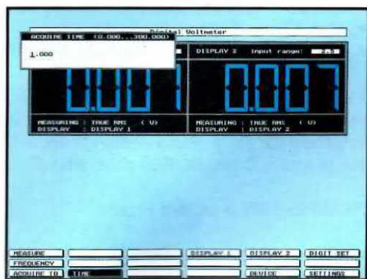
Fig.33 Se portate il cursore su Time poi pigiate Enter potrete cambiare il tempo dei dati di acquisizione da 0,5 secondi fino ad un massimo di 300 secondi.
