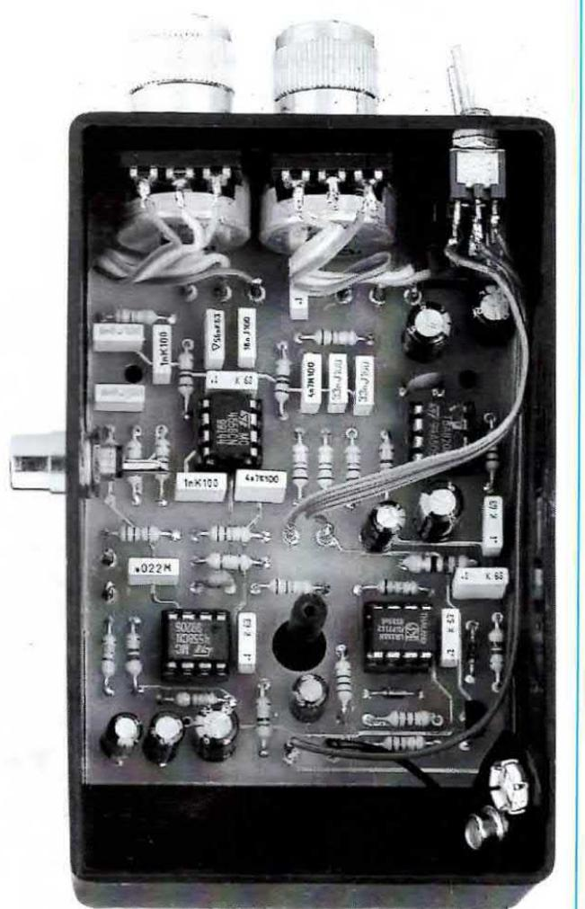
Fig.6 Schema pratico di montaggio. E' consigliabile collegare la carcassa metallica del potenziometro del Volume sul terminale collegato alla massa del circuito stampato.
