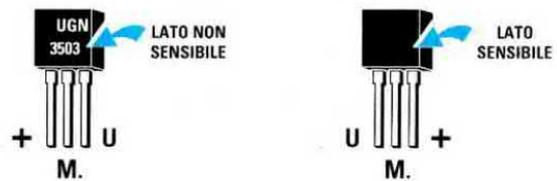
Fig.5 Connessioni dei tre terminali + M U del sensore di Hall viste dal lato della sigla e dal lato opposto. Il lato da passare sulla scheda è quello di destra.
