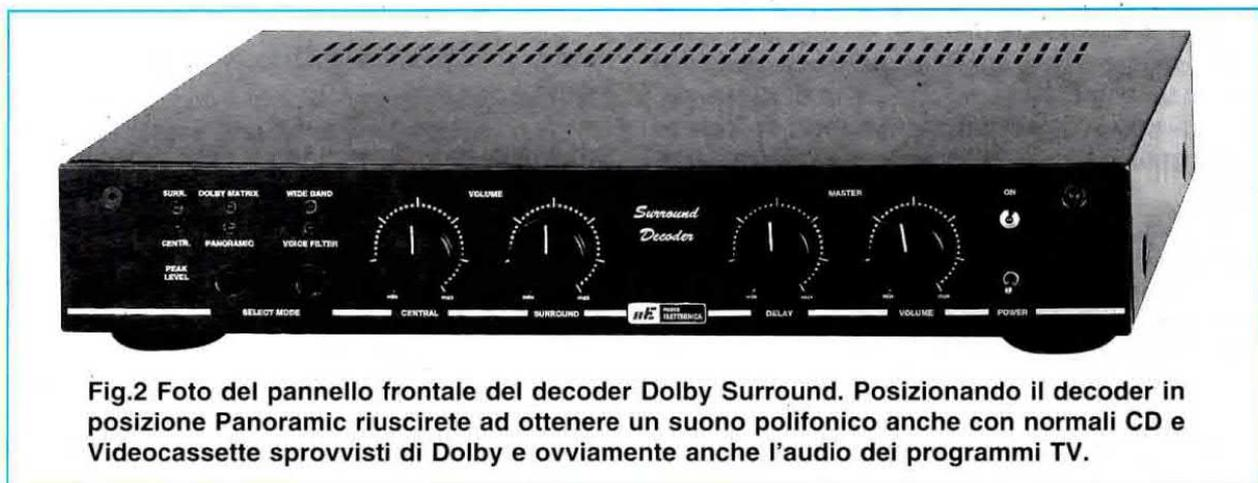
Fig.2 Foto del pannello frontale del decoder Dolby Surround. Posizionando il decoder in posizione Panoramic riuscirete ad ottenere un suono polifonico anche con normali CD e Videocassette sprovvisti di Dolby e ovviamente anche l'audio dei programmi TV.
