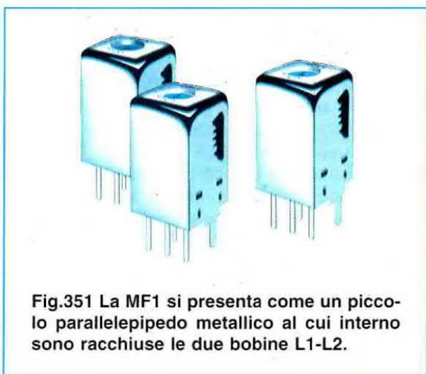
Fig.351 La MF1 si presenta come un piccolo parallelepipedo metallico al cui interno sono racchiuse le due bobine L1-L2.
