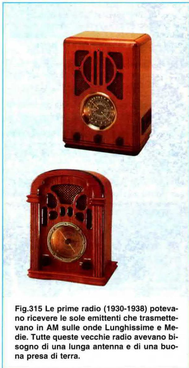
**Fig.315** Le prime radio (1930-1938) potevano ricevere le sole emittenti che trasmettevano in AM sulle onde Lunghissime e Medie. Tutte queste vecchie radio avevano bisogno di una lunga antenna e di una buona presa di terra.
