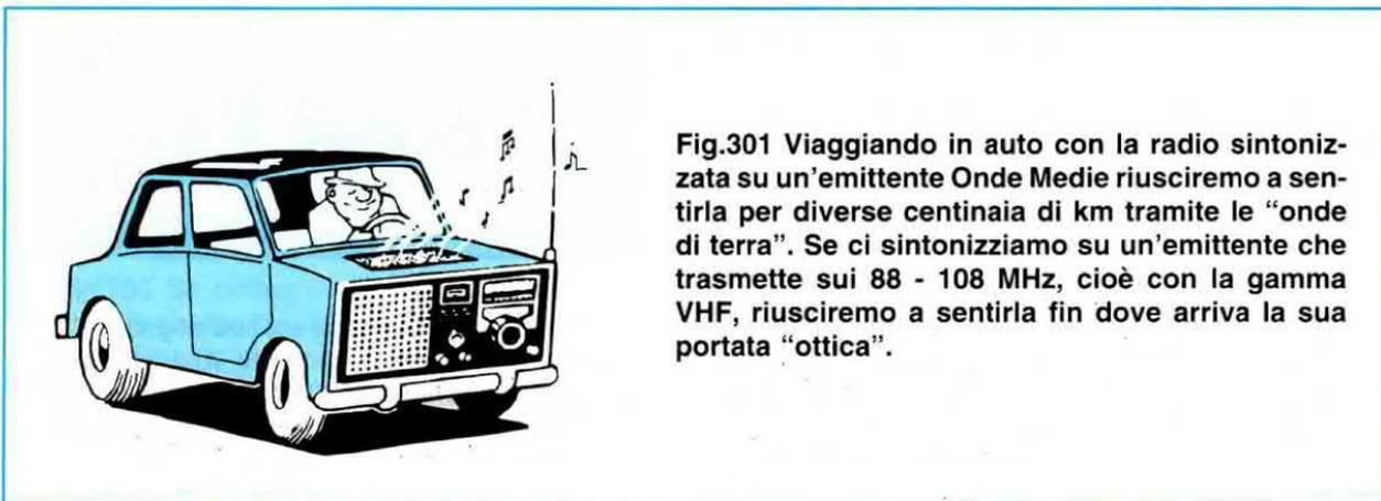
**Fig.301** Viaggiando in auto con la radio sintonizzata su un'emittente Onde Medie riusciremo a sentirla per diverse centinaia di km tramite le "onde di terra". Se ci sintonizziamo su un'emittente che trasmette sui 88 - 108 MHz, cioè con la gamma VHF, riusciremo a sentirla fin dove arriva la sua portata "ottica".
