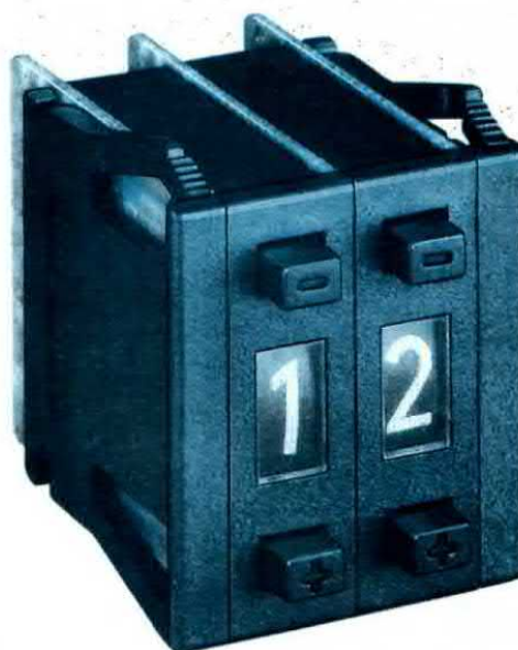
Fig.400 Nei commutatori digitali è presente una finestra in cui appare un numero da 0 a 9. In questa foto potete osservare due commutatori digitali appaiati.
