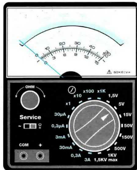
Fig.375 Nella funzione Voltmetro o Amperometro AC il valore della tensione o della corrente Alternata andrà letto sulla scala colorata in rosso. Prima di effettuare una misura AC, dovete ricordare di spostare la leva del microinterruttore dalla posizione CC-OHM alla posizione AC.
