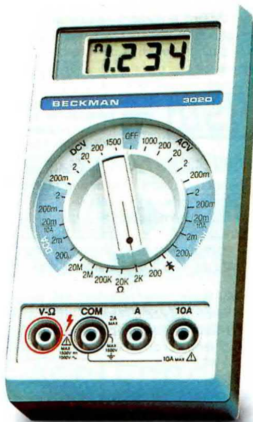
Fig.380 Tutte le portate dei Tester Digitali sono sempre dei multipli di 2 perchè il massimo numero che si riesce a visualizzare è 1.999. Il "punto" che appare sui display equivale ad una virgola quindi 1.234 ohm corrispondono a 1,234 kilohm.
