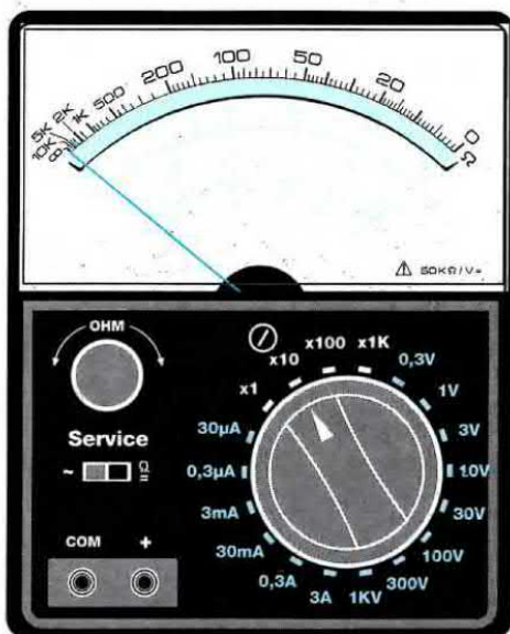
Fig.372 Nella funzione Ohmetro, il valore della resistenza letto sulla scala Ohm andrà moltiplicato per il fattore contrassegnato dalla manopola, cioè \times 1 - \times 10 - \times 100 - \times 1K . Ogni volta che cambierete portata dovete cortocircuitare i due puntali e ritoccare il potenziometro di taratura.
