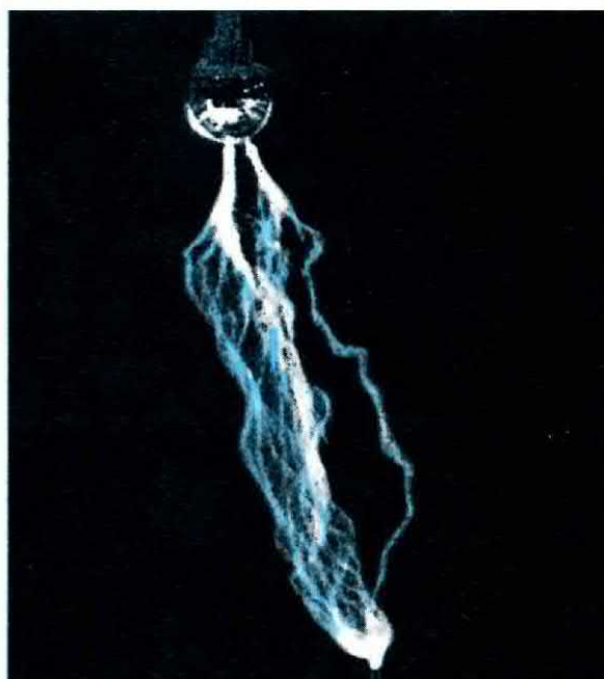
Fig.7 Se all'estremità della bobina collocherete la sola punta irradiante otterrete ugualmente delle vistose scariche elettriche che si dirameranno verso l'alto. Se in sostituzione della punta metterete 3-4 aghi otterrete delle scariche più vistose.
