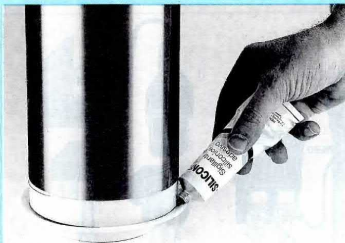
Fig.20 Sulla parte superiore del nostro trasformatore di Tesla dovreste fissare un piattino in ceramica con qualche goccia di cementatutto. Prima di farlo, dovreste aprire al centro un foro con una punta da 3,5 mm, in modo da stringere sotto ad una vite in ferro l'estremità del filo della bobina. Sopra alla vite avvitate la punta irradiante.
