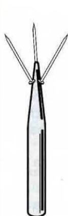
Fig.21 Se sulla punta irradiante fisserete 3-4 spilli o aghi, da ciascuno di essi fuoriusciranno delle vistose scintille.
