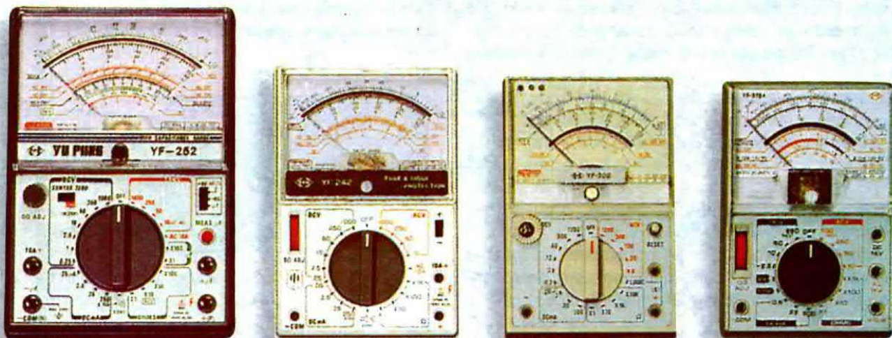
Fig.365 Se un giorno decideste di acquistare un Tester Analogico, sceglierne uno che abbia una sensibilità non inferiore a "20.000 ohm x volt" per ridurre gli errori di lettura.
