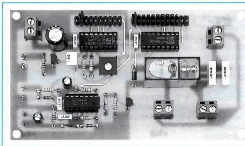
**Fig.10** Come si presenta a montaggio ultimato il temporizzatore LX.1305. La foto è notevolmente ridotta.
