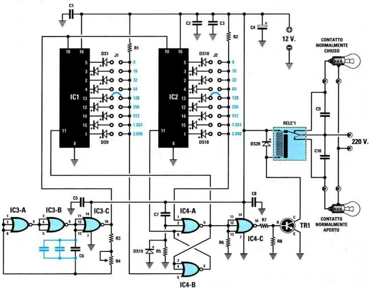
Fig.11 Schema elettrico del temporizzatore Ciclico siglato LX.1305. Volendo aumentare i tempi sarà sufficiente applicare in parallelo al condensatore C6 delle capacità supplementari. Il trimmer R4 si può sostituire con un potenziometro lineare da 220.000 ohm.
