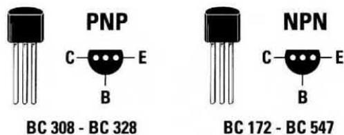
Anche se la forma e le connessioni CBE dei due transistor PNP e NPN sono identiche, sul corpo del transistor PNP è stampigliato BC.308 e sull'NPN BC.172.
