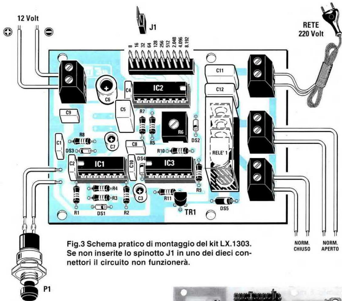
Fig.3 Schema pratico di montaggio del kit LX.1303. Se non inserite lo spinotto J1 in uno dei dieci connettori il circuito non funzionerà.
