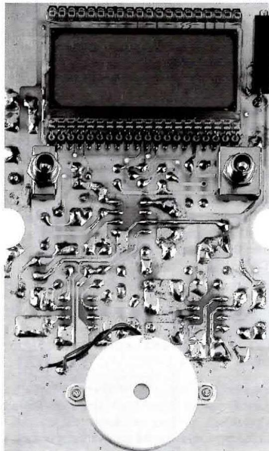
Fig.9 Lo stesso circuito di fig.8 visto dal lato dei display. Su tutti i circuiti stampati definitivi troverete un disegno serigrafico dei vari componenti ed una speciale vernice protettiva sulle piste in rame.
