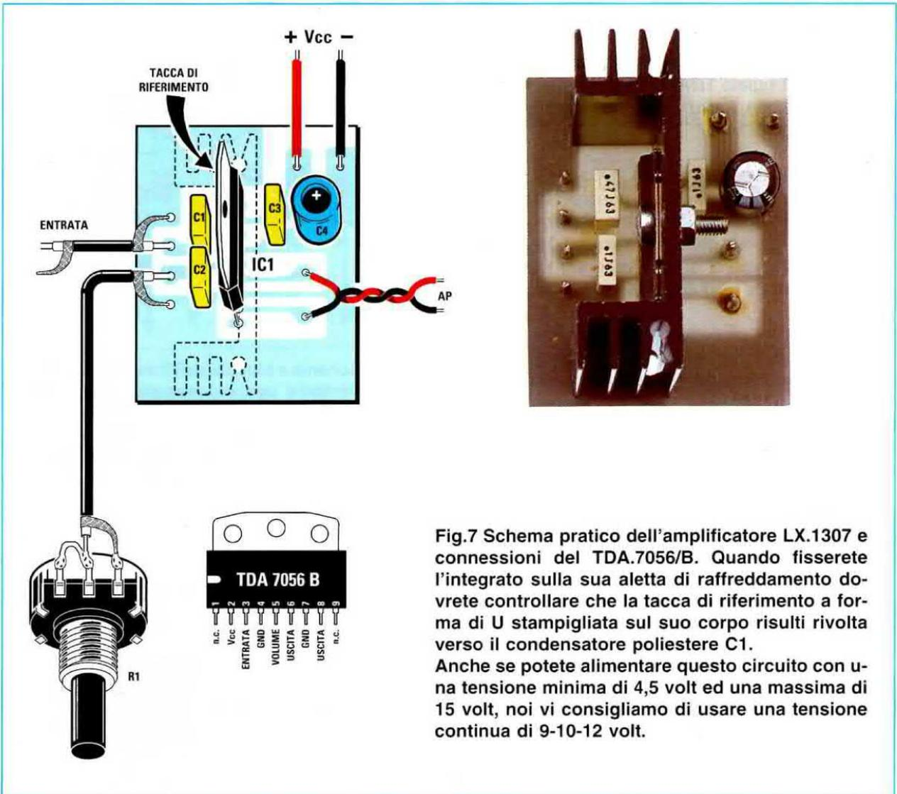
Fig.7 Schema pratico dell'amplificatore LX.1307 e connessioni del TDA.7056/B. Quando fisserete l'integrato sulla sua aletta di raffreddamento dovrete controllare che la tacca di riferimento a forma di U stampigliata sul suo corpo risulti rivolta verso il condensatore poliestere C1. Anche se potete alimentare questo circuito con una tensione minima di 4,5 volt ed una massima di 15 volt, noi vi consigliamo di usare una tensione continua di 9-10-12 volt.
