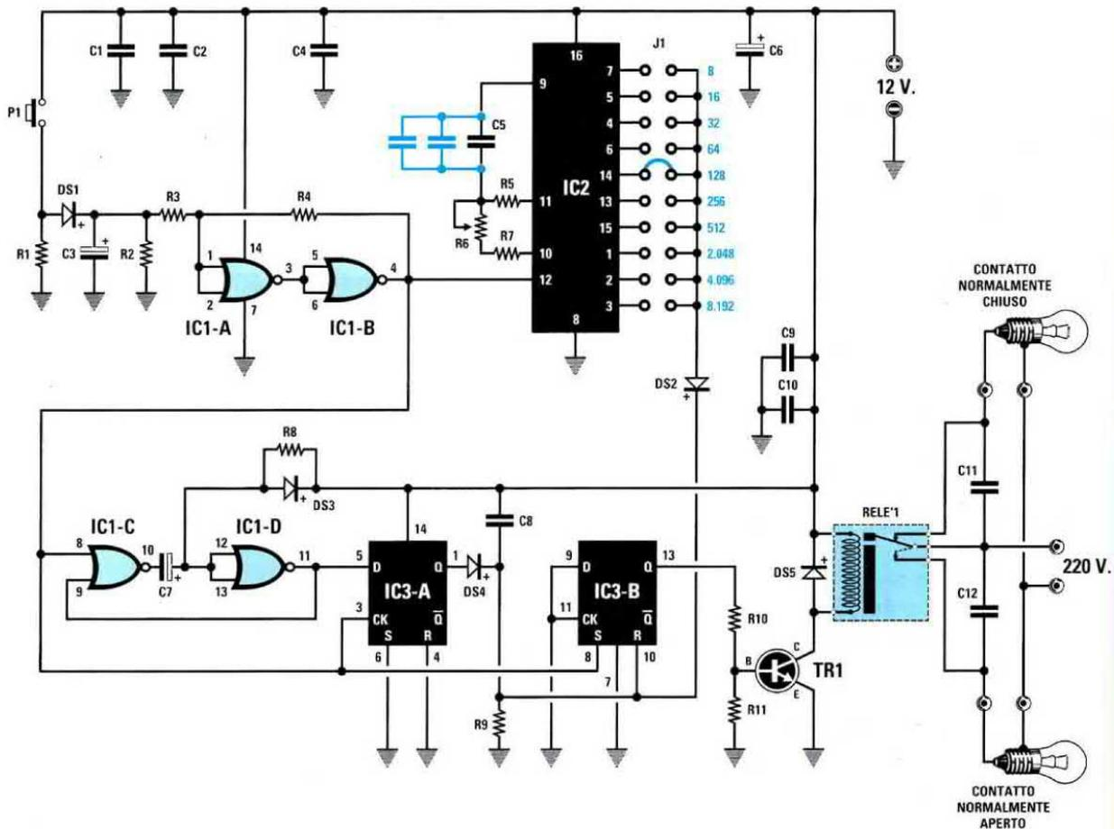
Fig.1 Schema elettrico del Temporizzatore per Luci Scale. Spostando lo spinotto J1 sulle varie uscite dell'integrato IC2 è possibile variare i tempi di eccitazione del relè da poche decine di secondi a diverse ore. Per aumentare i tempi è sufficiente collegare in parallelo al condensatore C5 degli altri condensatori in modo da aumentare la capacità totale. Regolando il cursore del trimmer R6 si ottengono precisi tempi di eccitazione.
