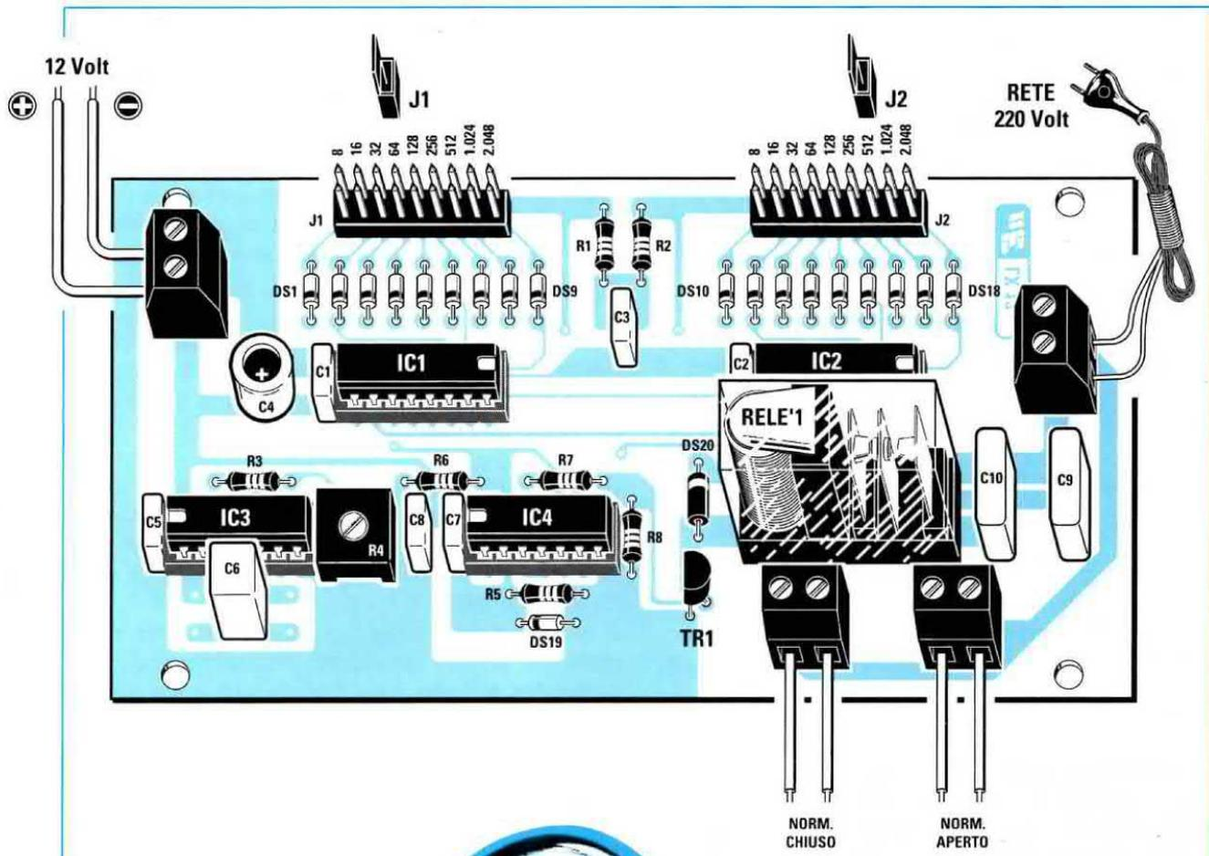
Fig.13 Schema pratico di montaggio del temporizzatore ciclico LX.1305.
