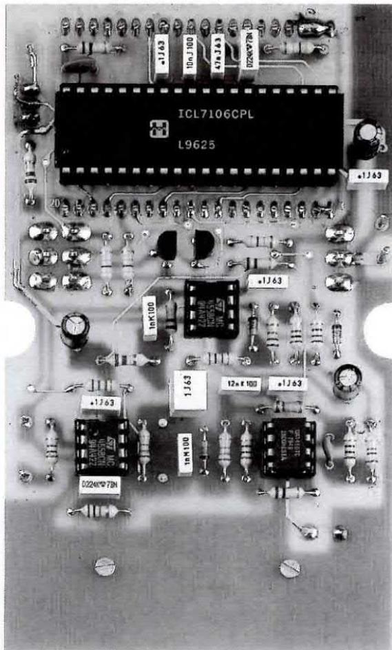
Fig.8 Foto di uno dei primi esemplari di Misuratore di Campi elettromagnetici, visto dal lato componenti, ai quali vengono quasi sempre apportate delle piccole modifiche per migliorarne le prestazioni.
