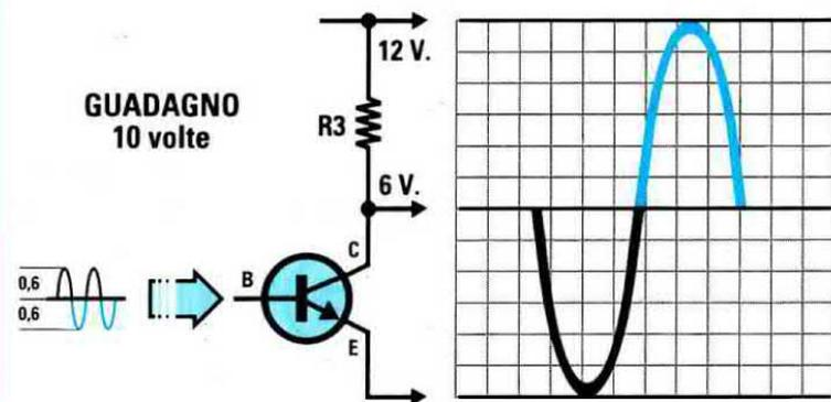
Fig.432 Se sul Collettore del transistor è presente "metà" tensione  $V_{cc}$ , potremo amplificare di 10 volte una sinusoide composta da una semionda positiva ed una negativa di 0,6 volt perchè il segnale amplificato rimarrà entro ai 12 quadretti.
