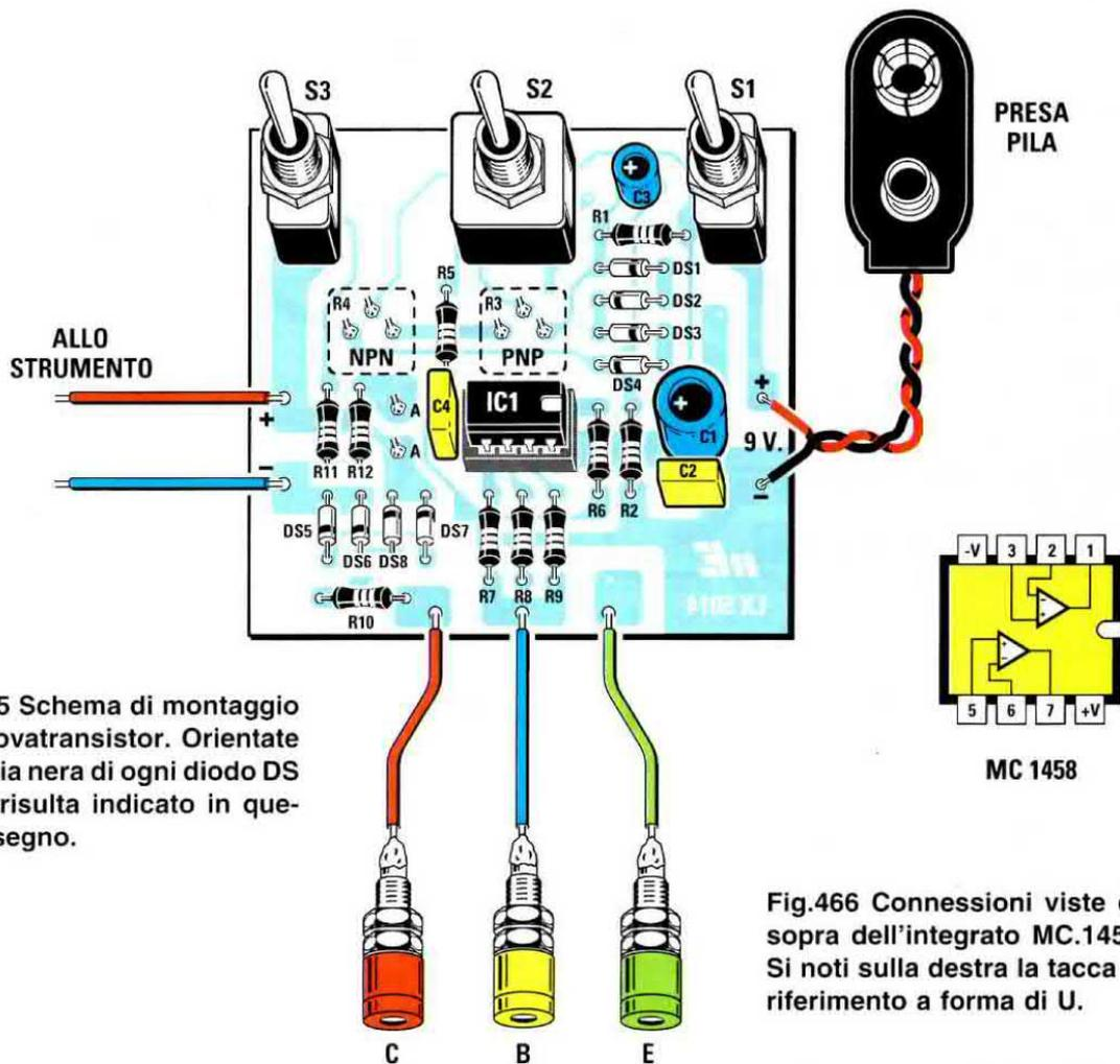
Fig.465 Schema di montaggio del provatransistor. Orientate la fascia nera di ogni diodo DS come risulta indicato in questo disegno.
