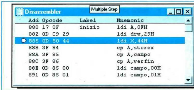
Fig.8 Se controllate con il software la finestra del Disassembler, potrete notare che l'istruzione: **ldi X,test01.d** si sarà tramutata in: **ldi X,44H**
