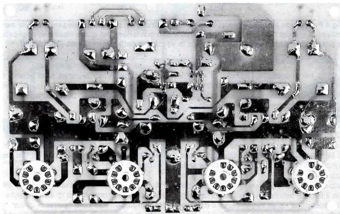
**Fig.4** Dal lato opposto del circuito stampato vanno fissati i quattro zoccoli ceramici delle valvole ECC.82. In questa foto, le piste in rame del circuito stampato non sono ancora protette con l'apposita vernice presente invece negli stampati forniti con i nostri kits.
