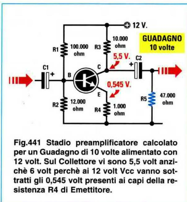
Fig.441 Stadio preamplificatore calcolato per un Guadagno di 10 volte alimentato con 12 volt. Sul Collettore vi sono 5,5 volt anziché 6 volt perchè ai 12 volt Vcc vanno sottratti gli 0,545 volt presenti ai capi della resistenza R4 di Emettore.
