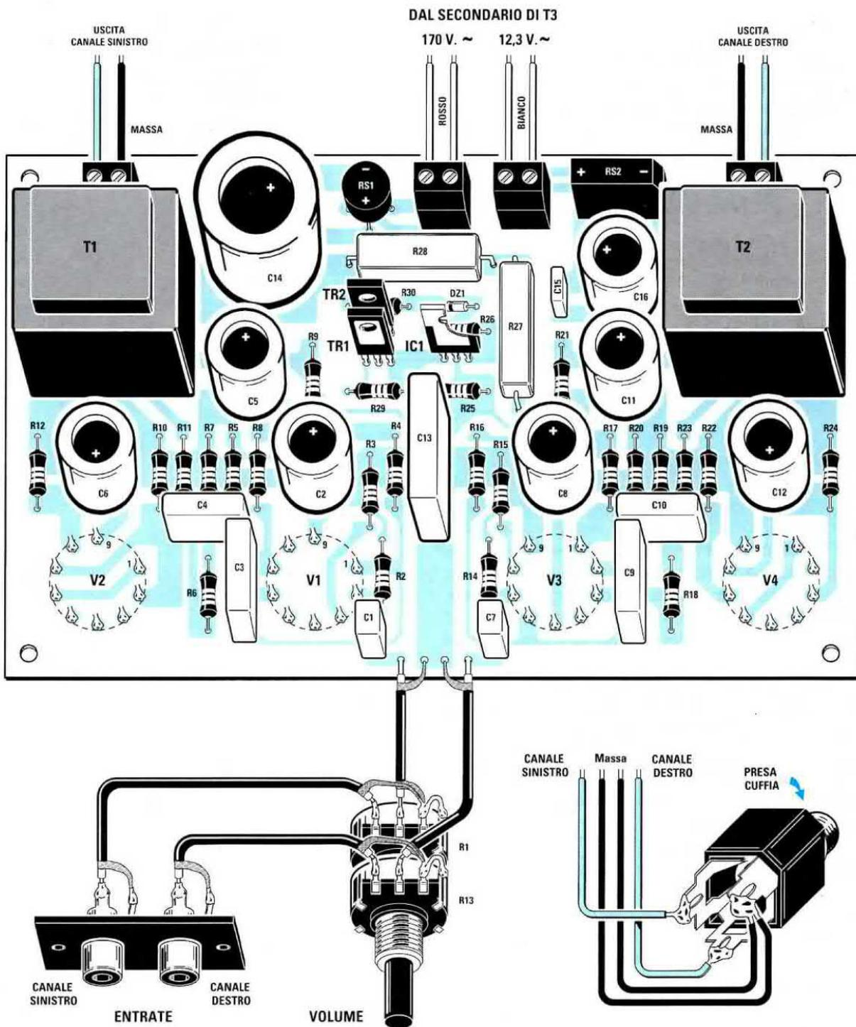
Fig.6 Schema pratico di montaggio dell'amplificatore valvolare per cuffia. Quando collegate le morsettiere dei trasformatori d'uscita T1-T2 alla presa di uscita Stereo della Cuffia dovete collegare i due fili di "massa" (filo nero) al terminale che collega alla massa il corpo metallico della presa. Se collegherete il filo del segnale (filo blu) al terminale di massa della presa d'uscita, in cuffia non ascolterete nessun suono.
