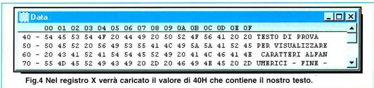
Fig.4 Nel registro X verrà caricato il valore di 40H che contiene il nostro testo.
