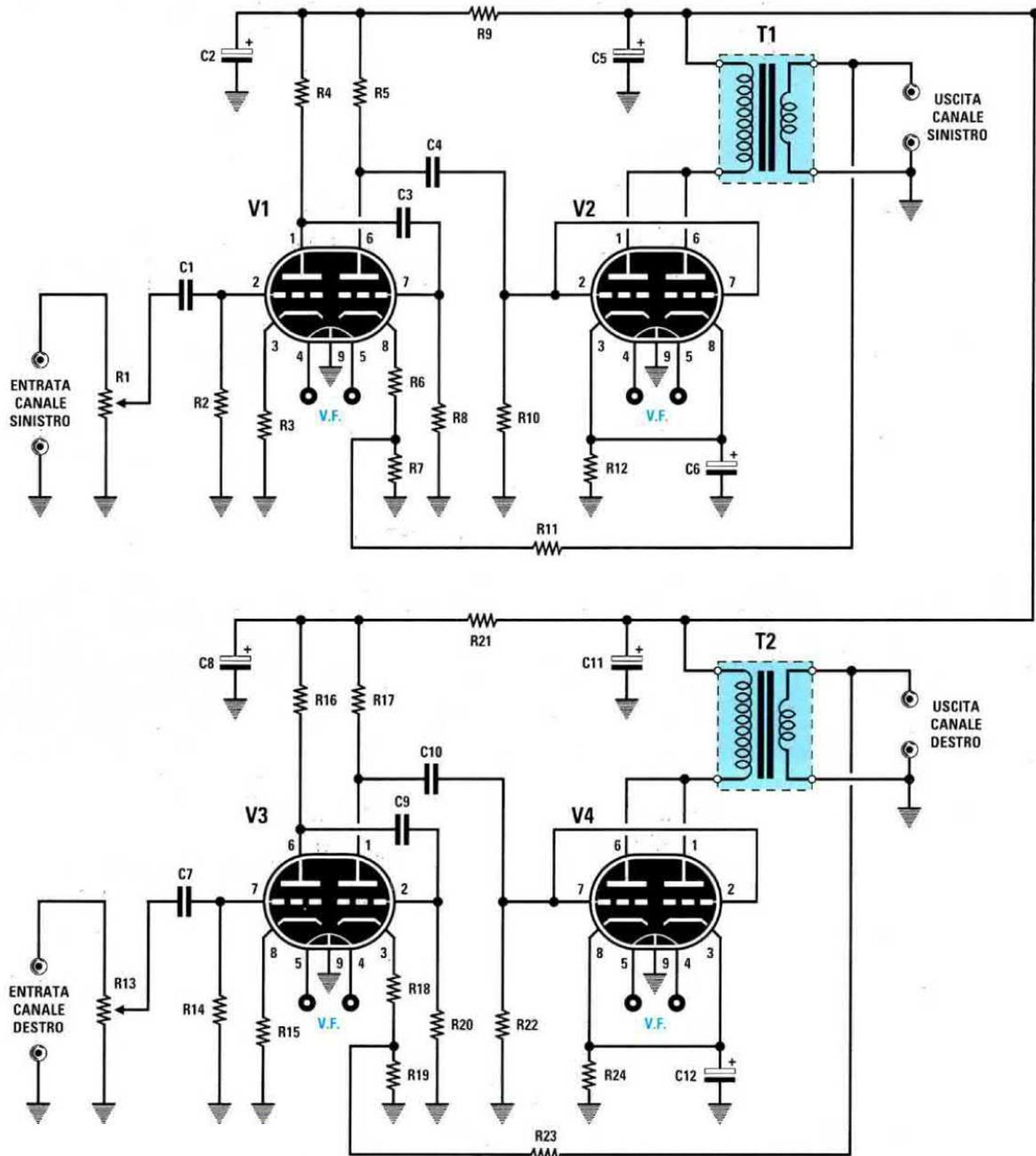
Fig.1 Schema elettrico dell'amplificatore Stereo LX.1309.
