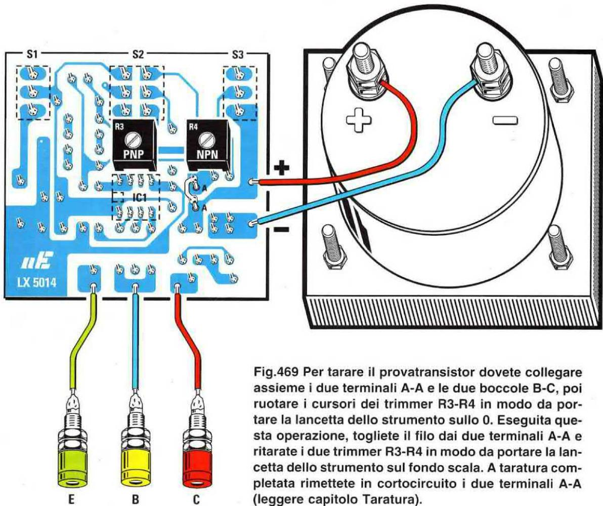
Fig.469 Per tarare il provatransistor dovete collegare assieme i due terminali A-A e le due boccole B-C, poi ruotare i cursori dei trimmer R3-R4 in modo da portare la lancetta dello strumento sullo 0. Eseguita questa operazione, togliete il filo dai due terminali A-A e ritarate i due trimmer R3-R4 in modo da portare la lancetta dello strumento sul fondo scala. A taratura completa rimettete in cortocircuito i due terminali A-A (leggere capitolo Taratura).
