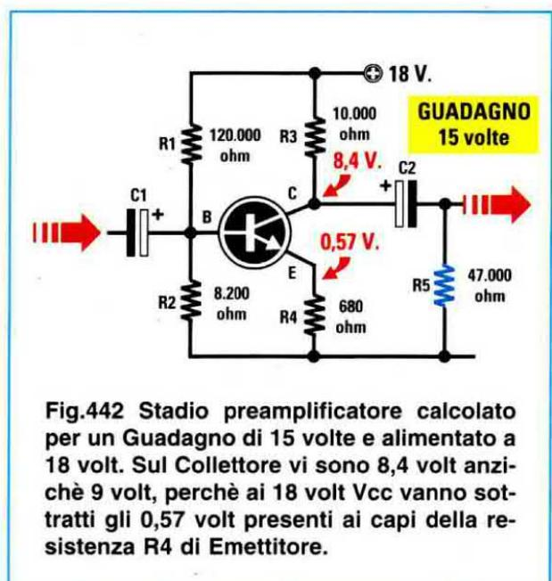
Fig.442 Stadio preamplificatore calcolato per un Guadagno di 15 volte e alimentato a 18 volt. Sul Collettore vi sono 8,4 volt anziché 9 volt, perchè ai 18 volt Vcc vanno sottratti gli 0,57 volt presenti ai capi della resistenza R4 di Emettore.
