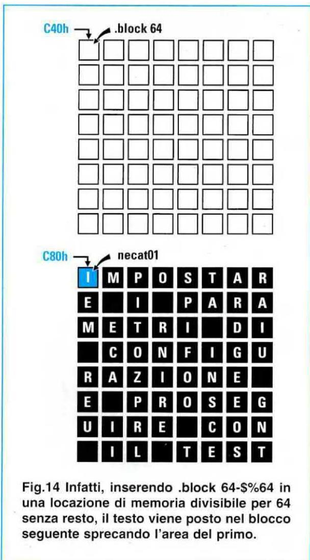
Fig.14 Infatti, inserendo **.block 64-\$%64** in una locazione di memoria divisibile per 64 senza resto, il testo viene posto nel blocco seguente sprecando l'area del primo.
