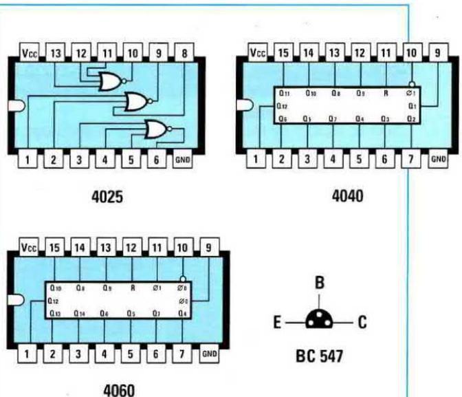
**Fig.7 Connessioni viste da sopra dei tre integrati utilizzati in questo progetto e del transistor BC.547 viste invece da sotto.**
