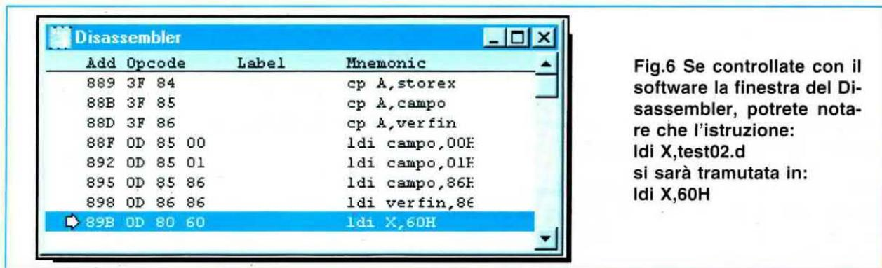
Fig.6 Se controllate con il software la finestra del Disassembler, potrete notare che l'istruzione: **ldi X,test02.d** si sarà tramutata in: **ldi X,60H**
