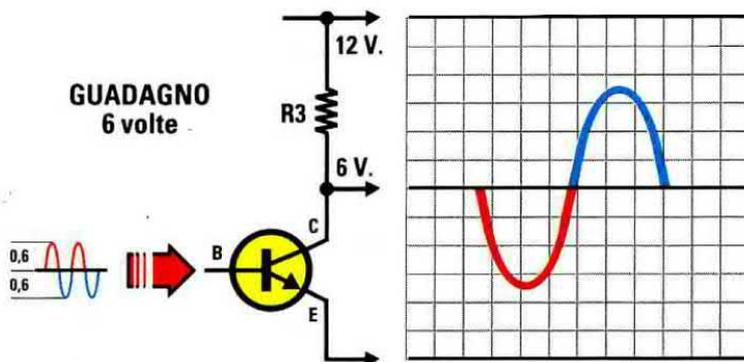
Fig.439 Se l'ampiezza del segnale che applicheremo sulla Base non riesce a scendere sotto agli  $0,6+0,6$  volt, per non correre il rischio di tosare le estremità delle due semionde dovremo ridurre il Guadagno portandolo da 10 volte a 6 volte.
