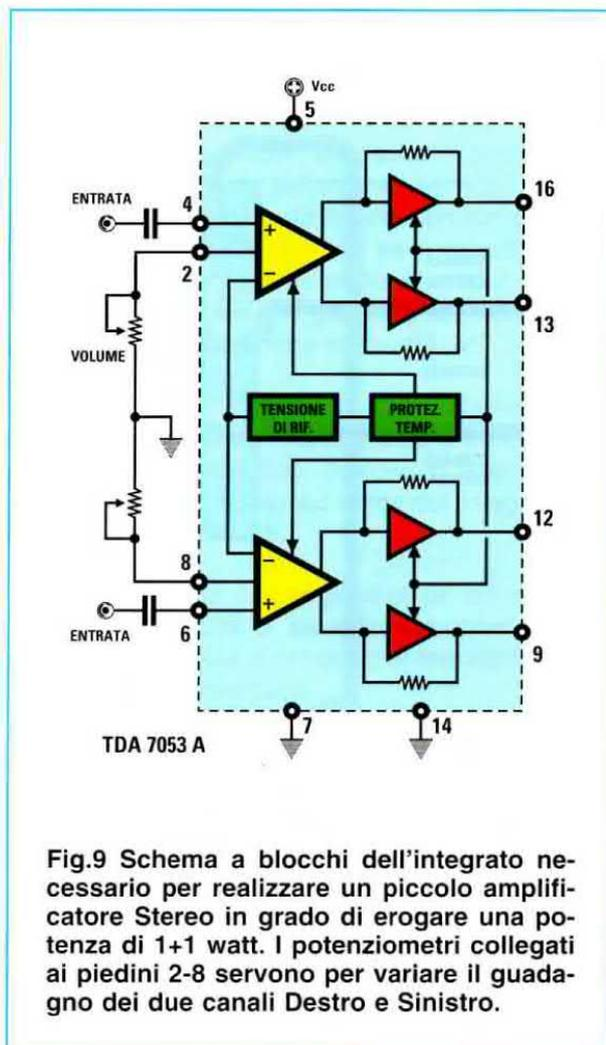
Fig.9 Schema a blocchi dell'integrato necessario per realizzare un piccolo amplificatore Stereo in grado di erogare una potenza di 1+1 watt. I potenziometri collegati ai piedini 2-8 servono per variare il guadagno dei due canali Destro e Sinistro.
