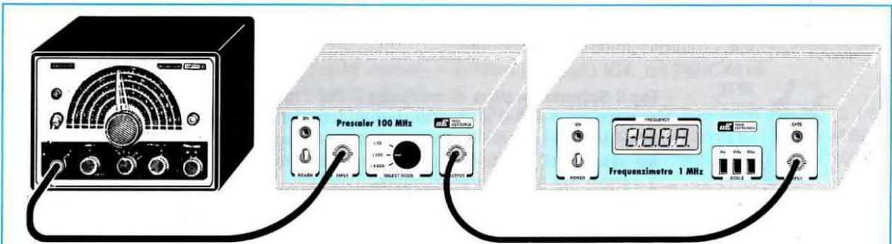
**Fig.6** Per tarare il Prescaler per la sua massima sensibilità, occorre applicare sul suo ingresso una frequenza di circa 40-60 MHz che potrete prelevare da un Generatore RF, poi ruotare il trimmer R3 fino a visualizzare sui display del frequenzimetro questa frequenza. Dopodichè dovrete "attenuare" il segnale sull'ingresso in modo da far sparire i numeri sui display, e poi ruotare lentamente il trimmer R3 fino a farli riapparire.
