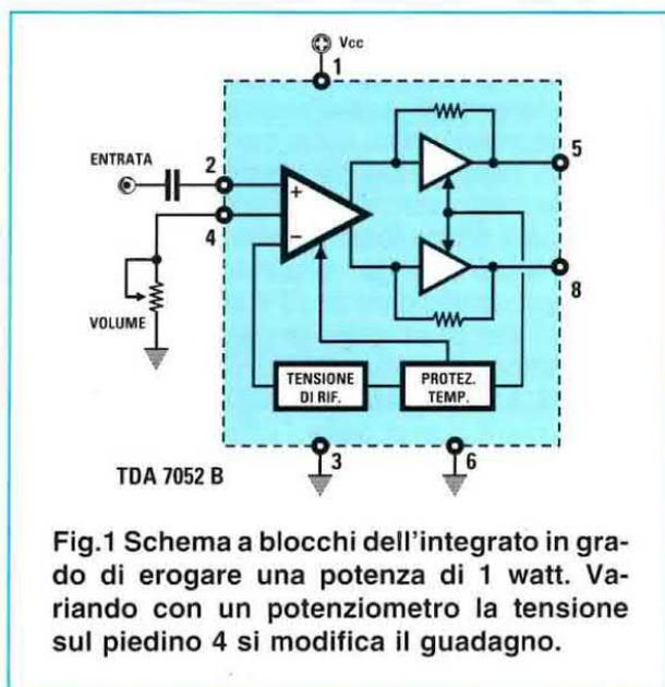
Fig.1 Schema a blocchi dell'integrato in grado di erogare una potenza di 1 watt. Variando con un potenziometro la tensione sul piedino 4 si modifica il guadagno.
