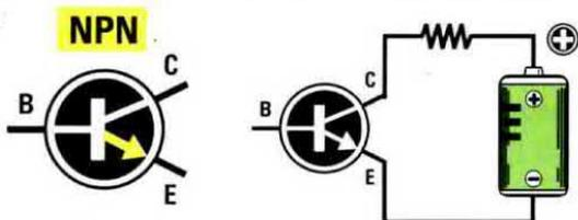
Fig.415 I transistor NPN si riconoscono dalla "freccia" posta sul terminale Emittore che risulta rivolta verso l'esterno. In questi transistor il Collettore va sempre collegato al Positivo di alimentazione.
