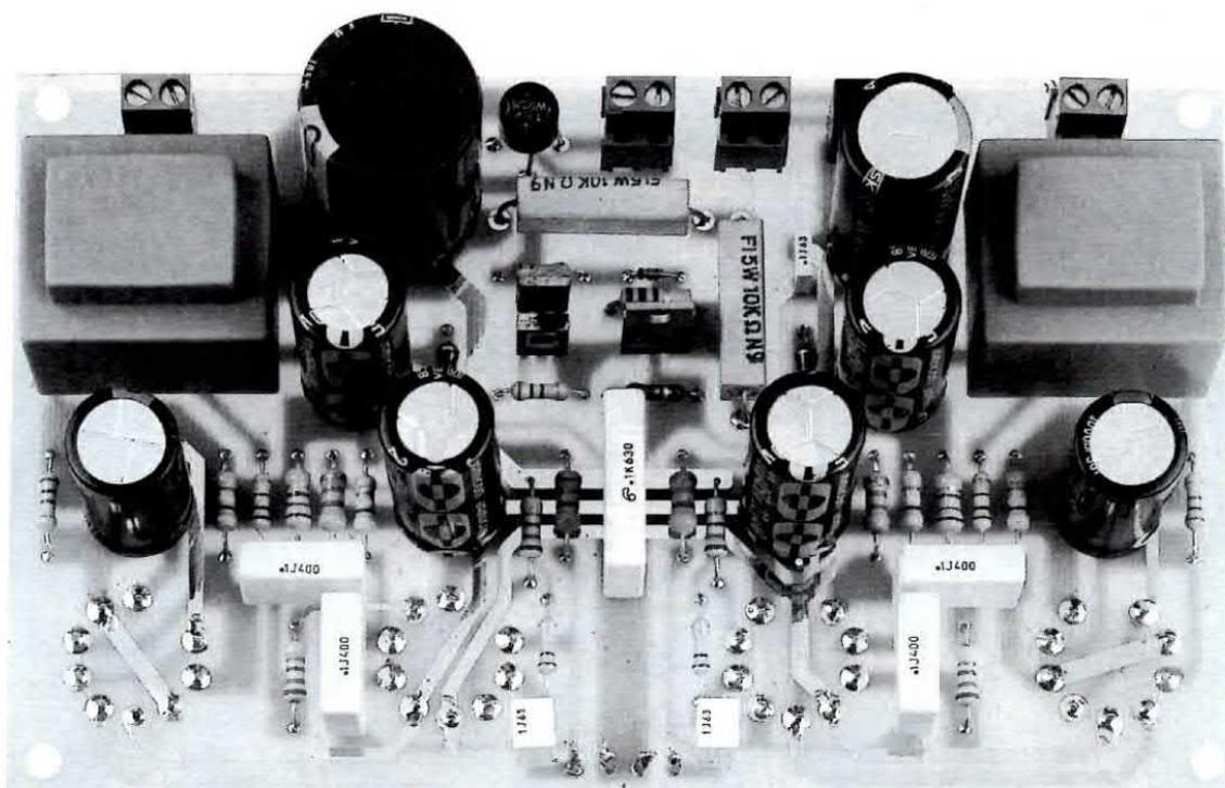
**Fig.3** Foto del circuito stampato LX.1309 visto dal lato dei componenti. Vi consigliamo di tenere il corpo delle due resistenze a filo R27-R28 distanziato di 1 mm circa dalla basetta del circuito stampato per evitare che il suo calore possa "cuocere" la vetronite.
