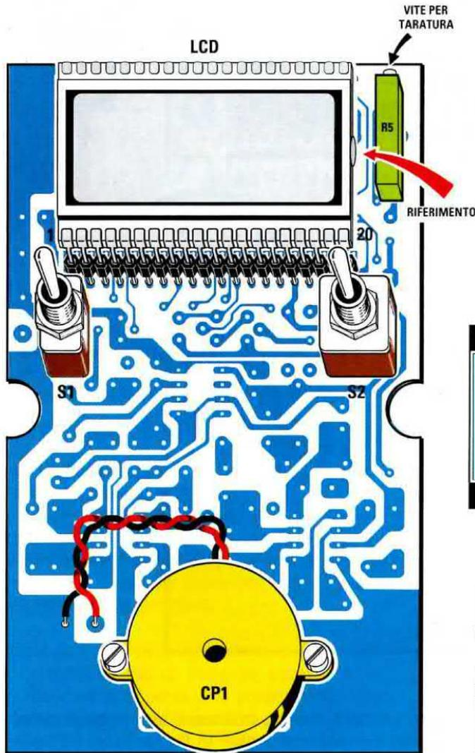
Fig.12 Quando inserite il display LCD nel circuito stampato dovrete controllare che la sua tacca di riferimento, costituita da una piccola protuberanza in vetro, risulti rivolta verso destra.
