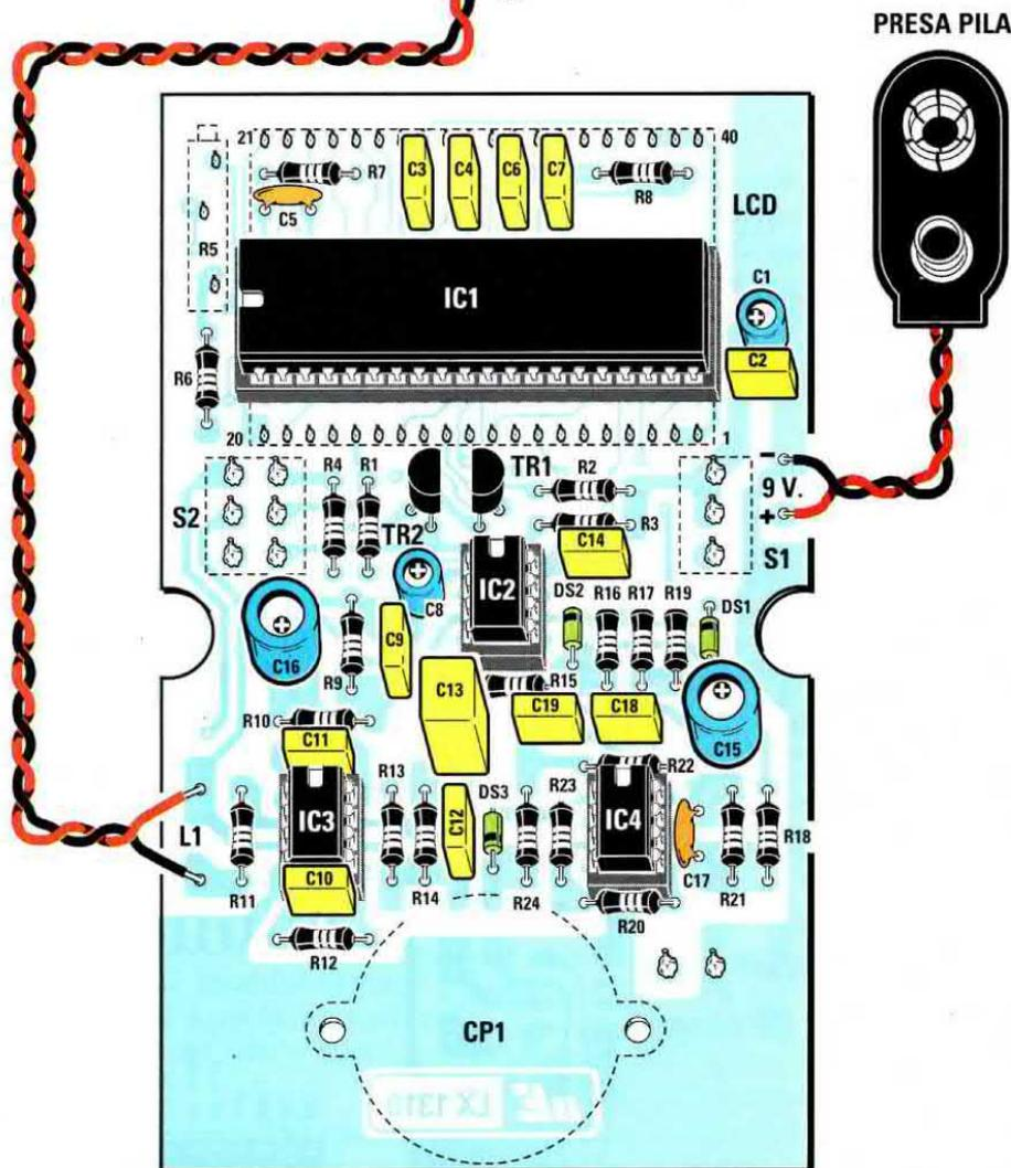
Fig.10 Su questo lato del circuito stampato LX.1310 dovreste collocare tutti i componenti visibili in disegno e, dal lato opposto, i pochi componenti visibili in fig.12. I due fili della bobina captatrice L1 non hanno una polarità, quindi possono essere tranquillamente invertiti sulle due piste in rame collocate in prossimità della resistenza R11.
