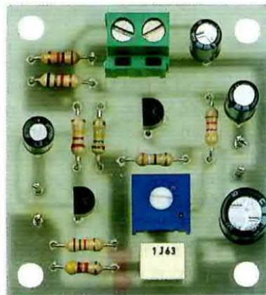
Per realizzare questo preamplificatore dovrete procurarvi il kit siglato **LX.5012** e seguendo lo schema pratico di fig.459 potrete montare nel circuito stampato tutti i componenti.
