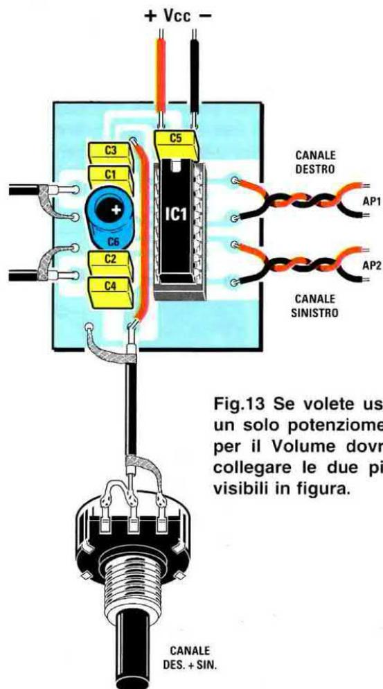
Fig.13 Se volete usare un solo potenziometro per il Volume dovrete collegare le due piste visibili in figura.
