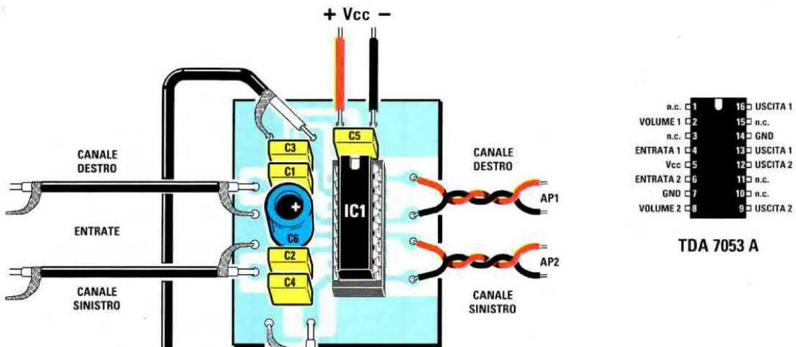
Fig.11 Schema pratico dell'amplificatore Stereo siglato LX.1308 e, sopra, le connessioni del TDA.7053/A. Ai fili di destra siglati AP1-AP2 vanno collegati due altoparlanti da 8 ohm.
