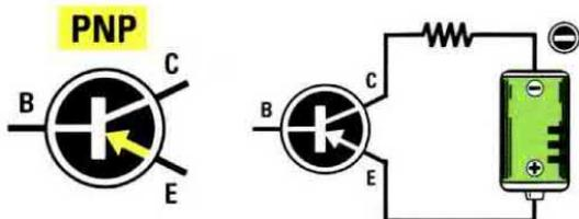
Fig.414 I transistor PNP si riconoscono dalla "freccia" posta sul terminale Emittore che risulta sempre rivolta verso la Base. In questi transistor il Collettore va collegato al Negativo di alimentazione.
