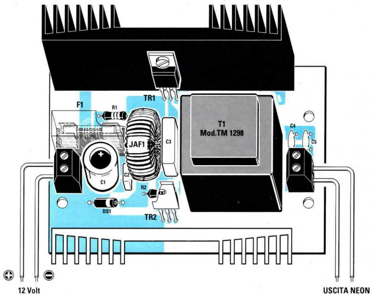
Fig.2 Schema pratico del kit LX.1298. Quando inserite i 12 volt nella morsetti di sinistra cercate di non invertire la polarità della batteria.
