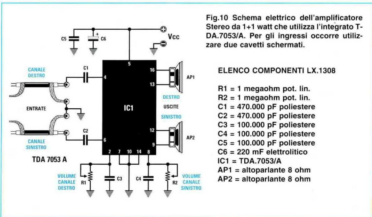
Fig.10 Schema elettrico dell'amplificatore Stereo da 1+1 watt che utilizza l'integrato T-DA.7053/A. Per gli ingressi occorre utilizzare due cavetti schermati.
