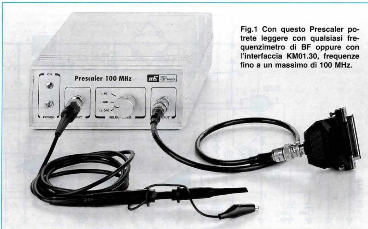
Fig.1 Con questo Prescaler potrete leggere con qualsiasi frequenzimetro di BF oppure con l'interfaccia KM01.30, frequenze fino a un massimo di 100 MHz.
