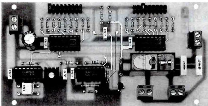
**Fig.5** Foto del temporizzatore **LX.1304** che permette di ottenere dei tempi **lunguissimi**. Lo schema elettrico è riportato in **fig.8**.
