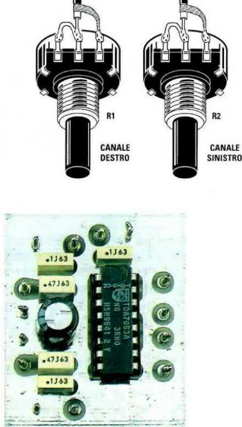
Fig.12 Ecco come si presenta a montaggio ultimato questo amplificatore Stereo. Per questo progetto non troverete il disegno del circuito stampato perchè è un doppia faccia con tutti i fori metallizzati.
