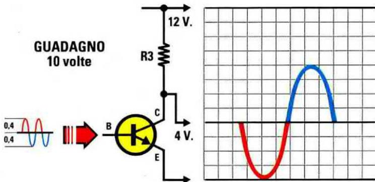
Fig.438 Se sul Collettore del transistor fosse presente una tensione di 4 volt anzichè di 6 volt, amplificando di 10 volte una sinusoide di  $0,4+0,4$  volt, la semionda inferiore non verrà tosata perchè non riuscirà mai a scendere sotto agli 0 volt.
