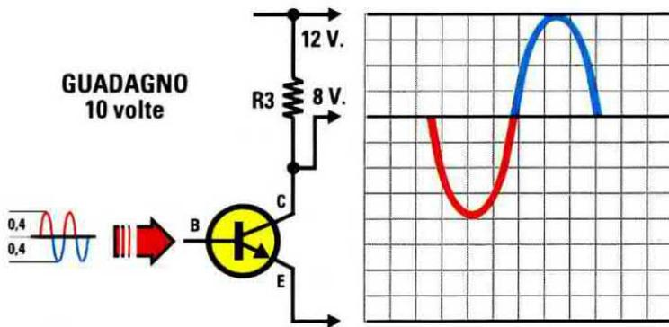
Fig.437 Se sul Collettore del transistor fosse presente una tensione di 8 volt anzichè di 6 volt, amplificando di 10 volte una sinusoide di  $0,4+0,4$  volt la semionda superiore non verrà tosata perchè non riuscirà a superare i 12 volt di alimentazione.
