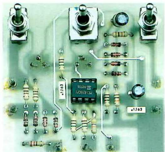
Fig.467 Foto del montaggio visto dal lato dei componenti. Tutte le piste in rame del circuito stampato che vi forniremo risulterà non appena protette da una vernice isolante.
