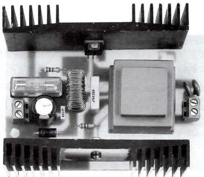
Se avete deciso per una lampada da **18 watt**, dovete inserire entrambi i condensatori **C4-C5**, se preferite una lampada da **10 watt** dovete inserire un **solo** condensatore, non importa se **C4** oppure **C5**.
