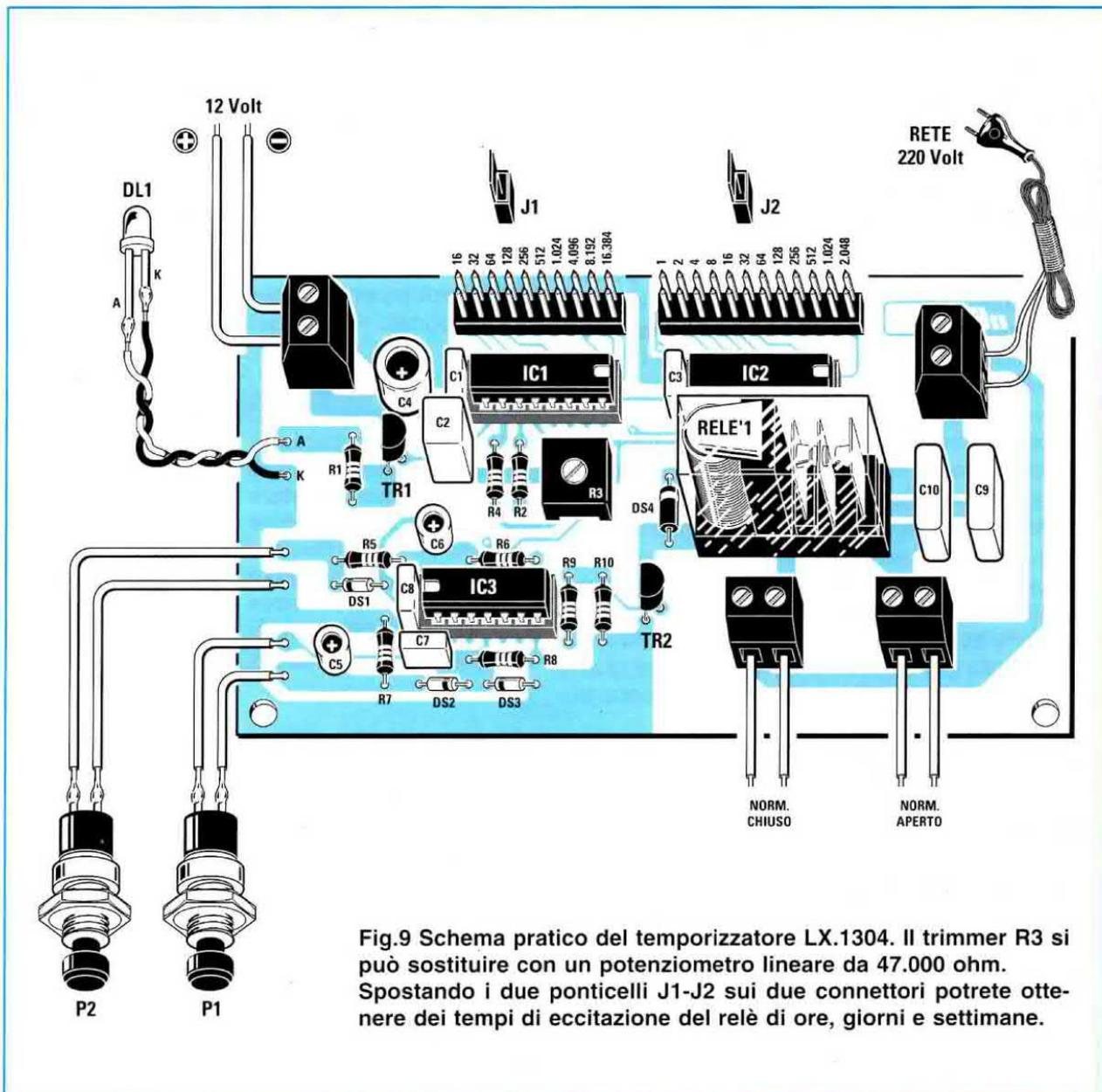
Fig.9 Schema pratico del temporizzatore LX.1304. Il trimmer R3 si può sostituire con un potenziometro lineare da 47.000 ohm. Spostando i due ponticelli J1-J2 sui due connettori potrete ottenere dei tempi di eccitazione del relè di ore, giorni e settimane.
