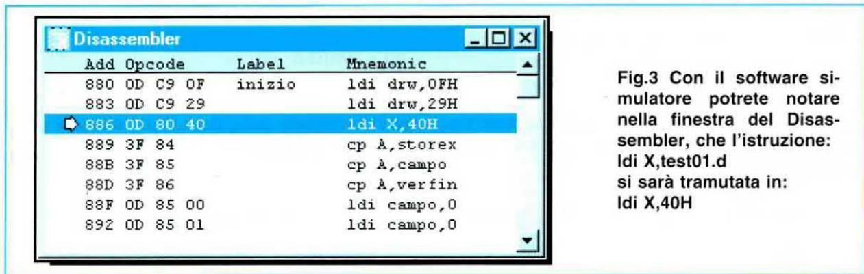
Fig.3 Con il software simulatore potrete notare nella finestra del Disassembler, che l'istruzione: **ldi X,test01.d** si sarà tramutata in: **ldi X,40H**
