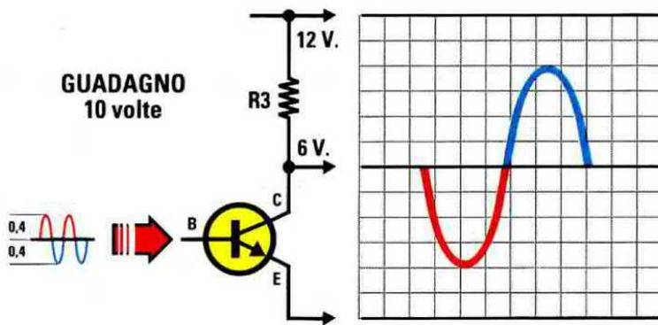
Fig.436 Per evitare che l'onda sinusoidale fuoriesca dal Collettore "tosata" su una delle due estremità, sarà sufficiente applicare sulla Base un segnale minore, ad esempio di  $0,4+0,4$  volt anzichè di  $0,6+0,6$  volt come abbiamo riportato in fig.432.
