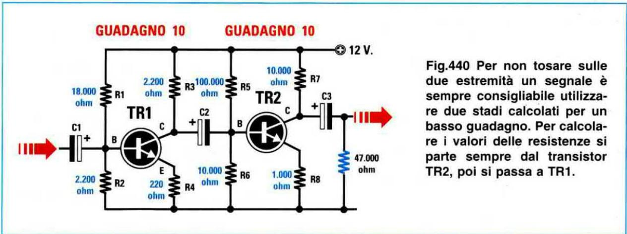
Fig.440 Per non tosare sulle due estremità un segnale è sempre consigliabile utilizzare due stadi calcolati per un basso guadagno. Per calcolare i valori delle resistenze si parte sempre dal transistor TR2, poi si passa a TR1.
