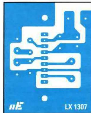
Fig.8 Disegno del circuito stampato siglato LX.1307, a grandezza naturale, visto dal lato rame. Utilizzando due stampati potrete realizzare uno Stereo da 5+5 watt.
