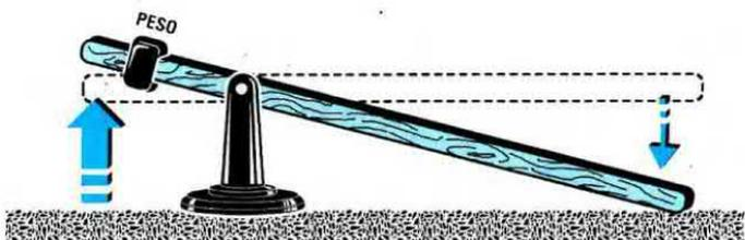
Fig.431 Se spingeremo verso l'alto il lato della Base, la parte opposta del Collettore si abbasserà fino a toccare il terreno e oltre a questa posizione non potrà più scendere.
