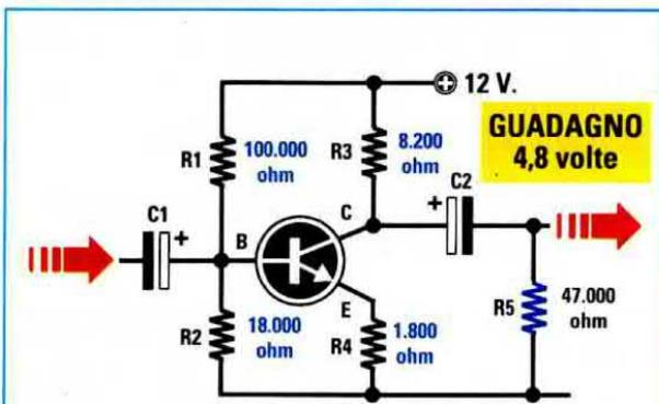
**Fig.445** Se dovete amplificare dei segnali che hanno delle ampiezze molto elevate, per evitare di **tosare** le due estremità delle semionde come visibile in fig.433, dovete ricalcolare tutti i valori delle resistenze **R1-R2-R3-R4** in modo da ridurre il guadagno. Con il valore riportato in questo schema e con una **VCC** di 12 volt si ottiene un guadagno di circa 4,8 volte.
