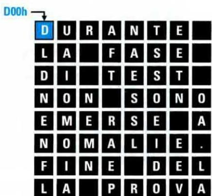
Fig.15 In questo esempio non è stata usata la direttiva `.ifc ne ($%64)` e per questo motivo il 1° e il 3° blocco sono vuoti.
