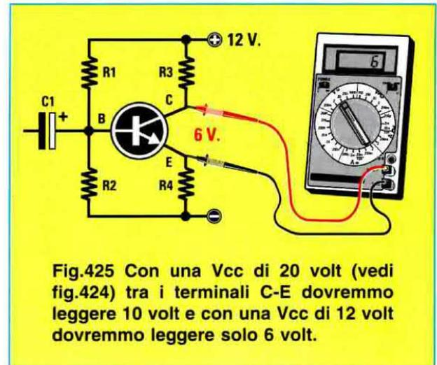
Solo quando sul **Collettore** risulta presente **metà tensione** di alimentazione avremo **dimezzato** il flusso degli elettroni e solo in questa condizione riusciremo ad **amplificare** i segnali applicati sulla **Base** senza nessuna **distorsione**.
