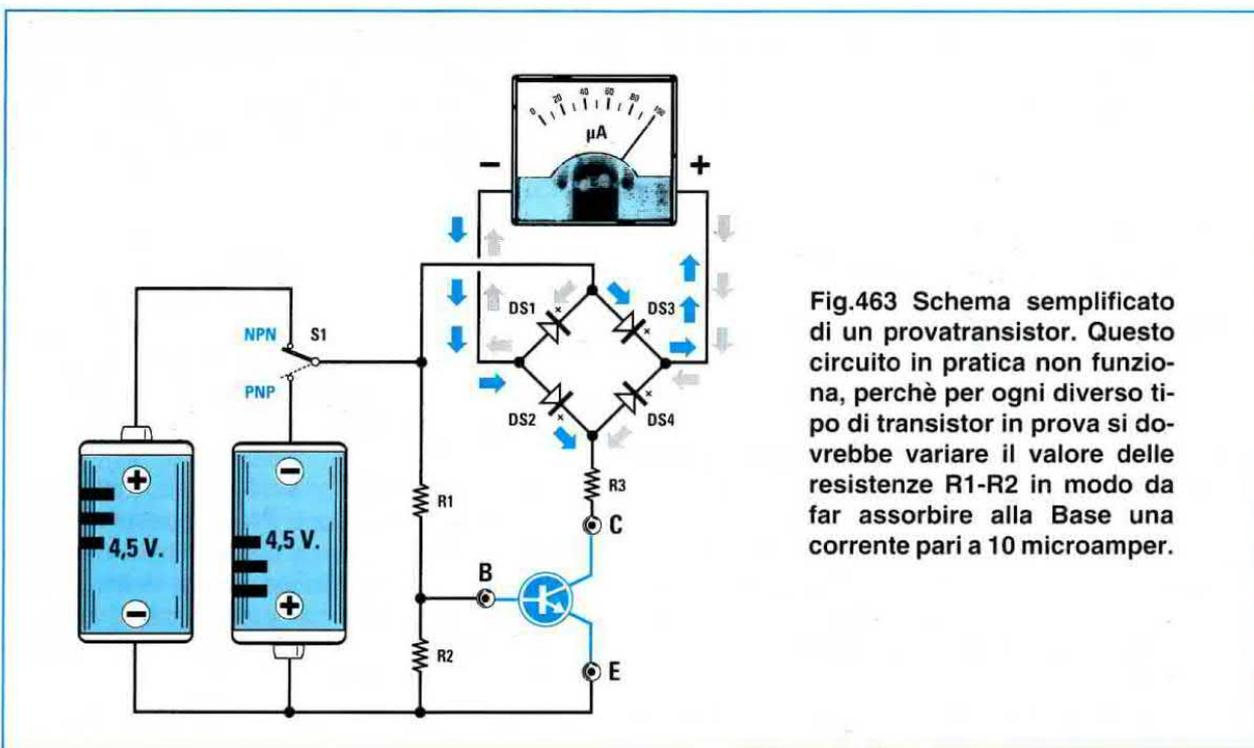
**Fig.463** Schema semplificato di un provatransistor. Questo circuito in pratica non funziona, perchè per ogni diverso tipo di transistor in prova si dovrebbe variare il valore delle resistenze R1-R2 in modo da far assorbire alla Base una corrente pari a 10 microamper.
