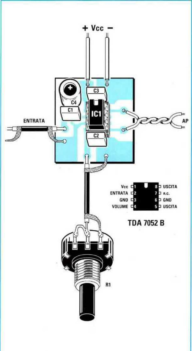
**Fig.4 Schema pratico dell'amplificatore LX.1306 e connessioni del TDA.7052/B viste da sopra. Ai due fili di destra siglati AP va collegato un altoparlante da 8 ohm.**
