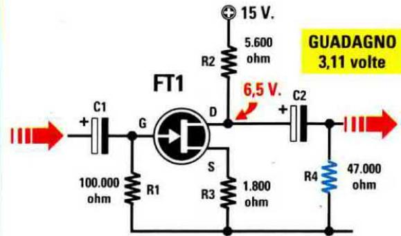
Fig.497 Scegliendo per la **R2** un valore di **5.600 ohm** e per la **R3** un valore di **1.800 ohm**, questo fet amplificherà i segnali applicati sul Gate di circa **3,11 volte**.
