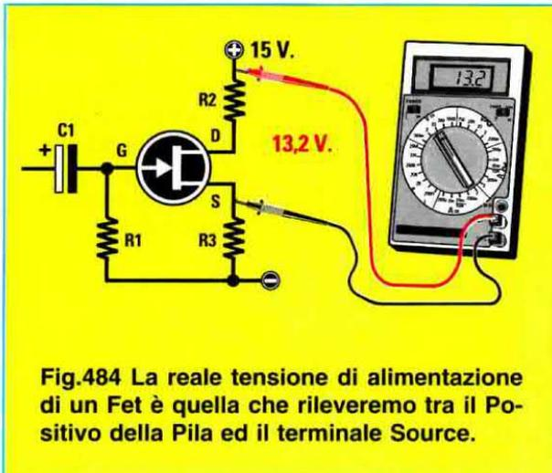
**Drain** e la **massa** risulta di **15 volt**, ma ai capi della resistenza **R3** collegata tra il **Source** e la **massa** è presente una tensione di **1,8 volt**, dovremo **sottrarre** questo valore ai **15 volt**. Il **Drain** del fet non risulterà perciò alimentato con **15 volt**, ma con una tensione di:
