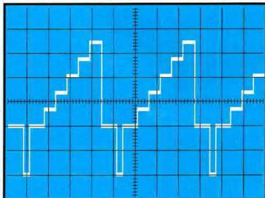
Fig.3 Collegando un oscilloscopio in parallelo alla resistenza **R13** posta sul terminale Emettore di **TR1** (vedi schema elettrico di fig.4) vedrete sullo schermo tutti gli scalini che creeranno le barre colori più il segnale del sincronismo.
