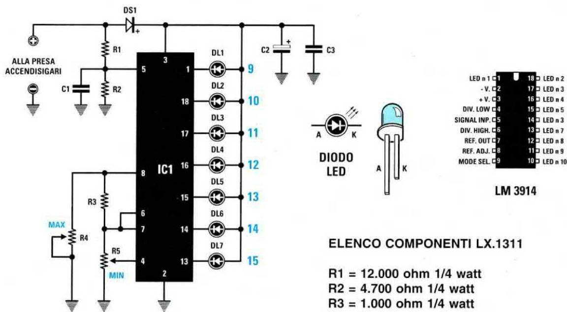
Fig.1 Schema elettrico e connessioni viste da sopra dell'integrato LM.3914. Il terminale più lungo dei diodi led è sempre l'A (anodo).
