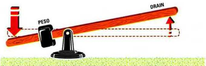
Fig.483 Se dalla posizione orizzontale spingeremo verso il basso il Gate la parte opposta di Drain si solleverà. L'onda sinusoidale che applicheremo sul Gate sposterà questa leva in alto o in basso.
