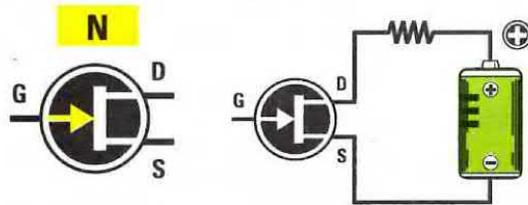
Fig.473 I Fet di canale N si riconoscono perchè la linea che parte dal terminale Gate ha una freccia rivolta verso l'interno. In questi Fet il terminale Drain va collegato al Positivo di alimentazione e il terminale Source va collegato al Negativo.
