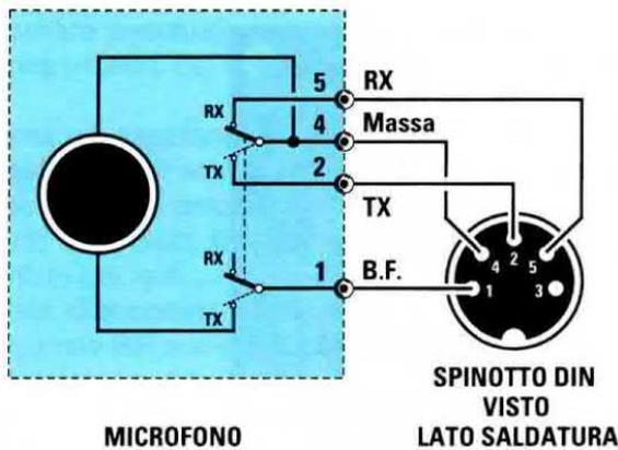
Fig.7 Il connettore di un normale microfono per ricetrasmittitore dispone di quattro fili, uno di massa (calza esterna del cavo schermato), uno per il segnale BF per predisporre il ricetrasmittitore in posizione ricezione (RX) ed uno per predisporlo in trasmissione (TX). Il passaggio da RX a TX si effettua premendo il pulsante presente sul corpo del microfono.
