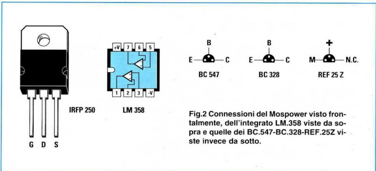
Fig.2 Connessioni del Mospower visto frontalmente, dell'integrato LM.358 viste da sopra e quelle dei BC.547-BC.328-REF.25Z viste invece da sotto.
