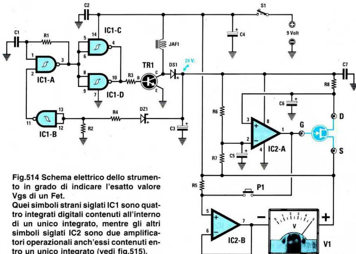
Fig.514 Schema elettrico dello strumento in grado di indicare l'esatto valore  $V_{gs}$  di un Fet. Quei simboli strani siglati IC1 sono quattro integrati digitali contenuti all'interno di un unico integrato, mentre gli altri simboli siglati IC2 sono due amplificatori operazionali anch'essi contenuti entro un unico integrato (vedi fig.515).
