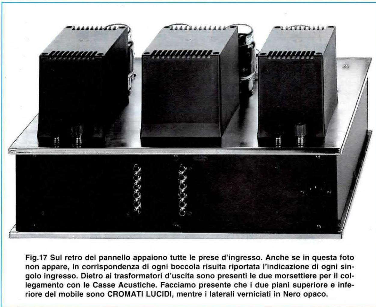
Fig.17 Sul retro del pannello appaiono tutte le prese d'ingresso. Anche se in questa foto non appare, in corrispondenza di ogni boccola risulta riportata l'indicazione di ogni singolo ingresso. Dietro ai trasformatori d'uscita sono presenti le due morsettiere per il collegamento con le Casse Acustiche. Facciamo presente che i due piani superiore e inferiore del mobile sono CROMATI LUCIDI, mentre i laterali verniciati in Nero opaco.
