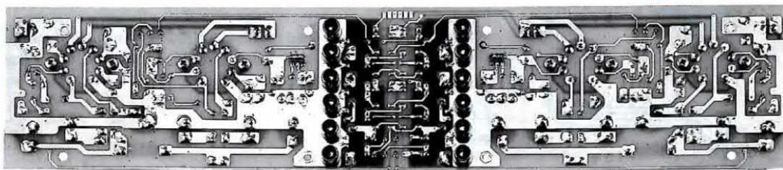
**Fig.6** Foto dello stadio preamplificatore Stereo siglato LX.1320 visto da entrambi i lati. Questa scheda andrà fissata sul pannello posteriore utilizzando i distanziatori metallici inseriti nel kit. Si notino i quattro schermi metallici applicati sulle valvole.
