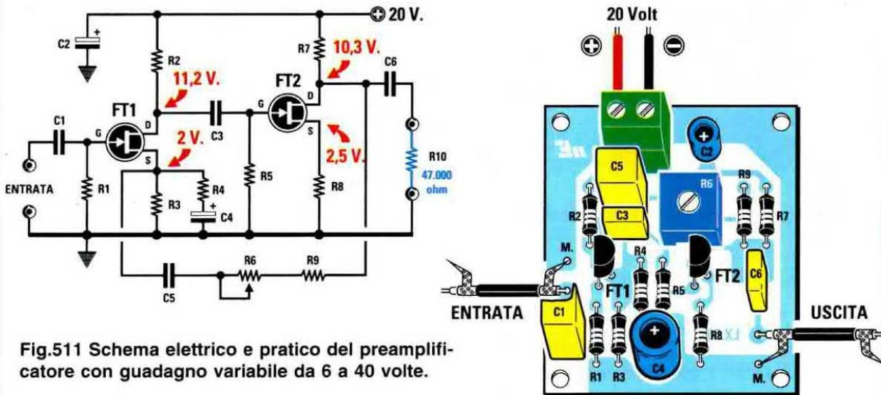
Fig.511 Schema elettrico e pratico del preamplificatore con guadagno variabile da 6 a 40 volte.
