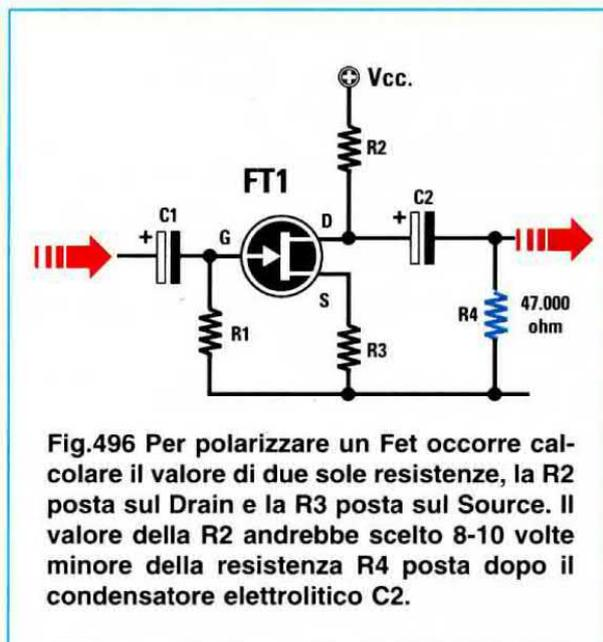
Fig.496 Per polarizzare un Fet occorre calcolare il valore di due sole resistenze, la R2 posta sul Drain e la R3 posta sul Source. Il valore della R2 andrebbe scelto 8-10 volte minore della resistenza R4 posta dopo il condensatore elettrolitico C2.
