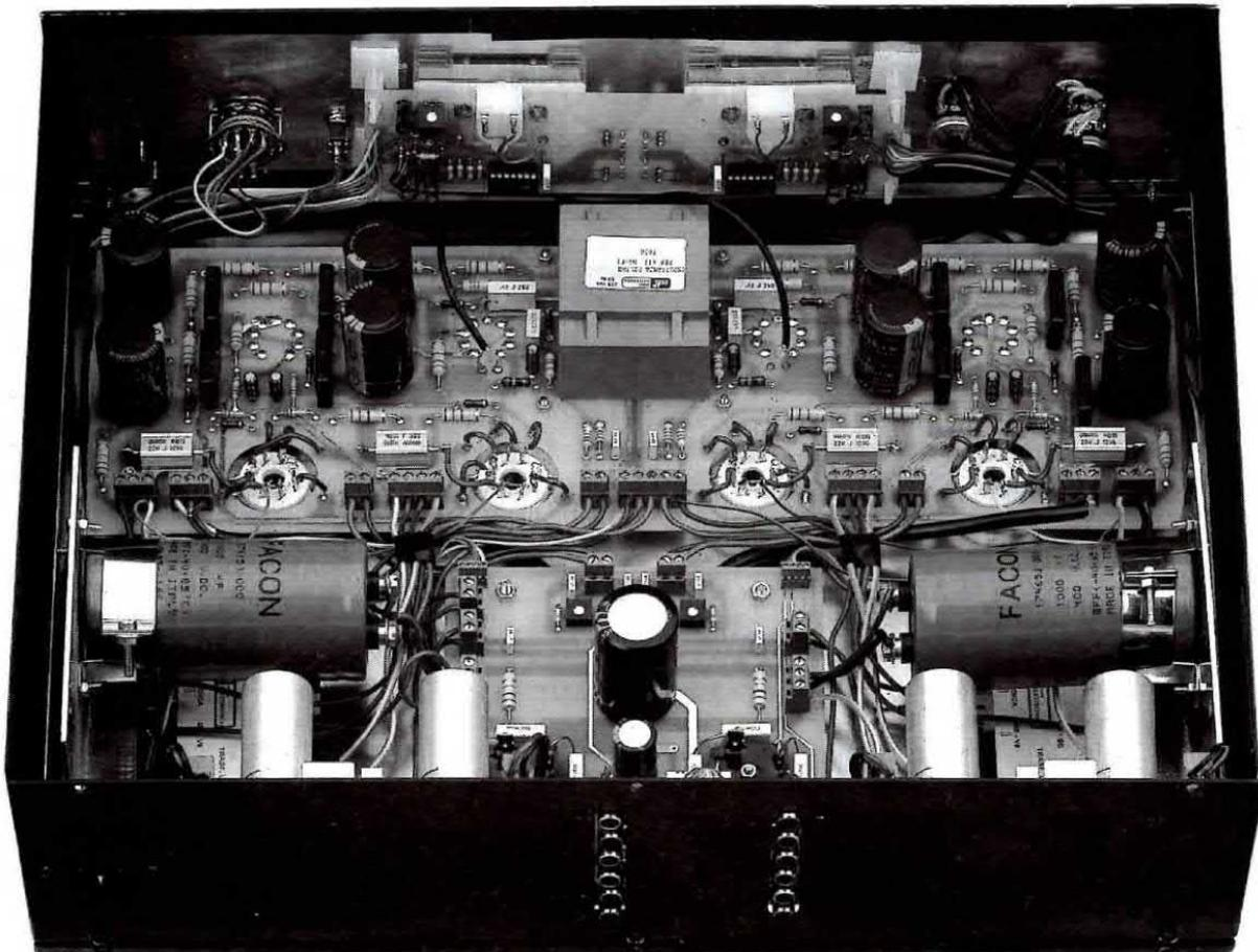
**Fig.16** In questa foto si può vedere come risulta fissato sul pannello anteriore lo stampato del Vu-Meter tramite i quattro distanziatori plastici con base autoadesiva. Anche se nella fig.14 abbiamo disegnato i due potenziometri R35/S-R35/D separati per rendere più visibili i collegamenti, in realtà si tratta di un doppio potenziometro come appare evidente osservando il lato destro del pannello.
