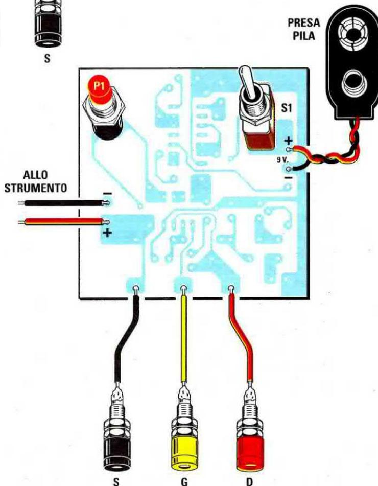
Fig.518 Dal lato opposto del cir-cuito stampato dovrete fissare sulla sinistra il pulsante P1 e sulla destra l'interruttore di accen-sione S1. Anche se in questo disegno appaiono tre boccole di colore Nero, Giallo e Rosso, non è da e-scludere che nel kit troviate una boccia Blu anzichè Gialla.
