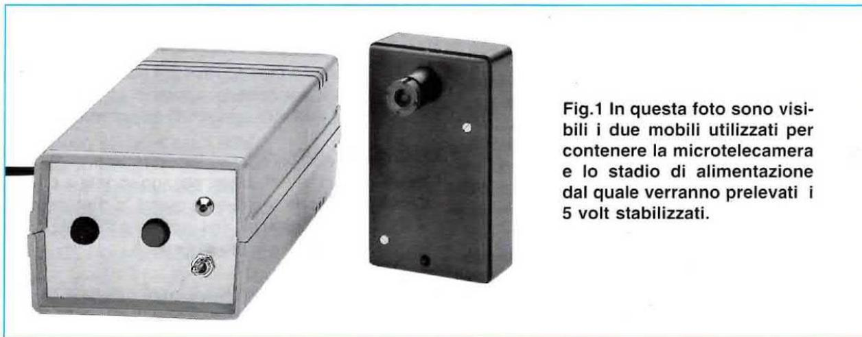
Fig.1 In questa foto sono visibili i due mobili utilizzati per contenere la microtelecamera e lo stadio di alimentazione dal quale verranno prelevati i 5 volt stabilizzati.
