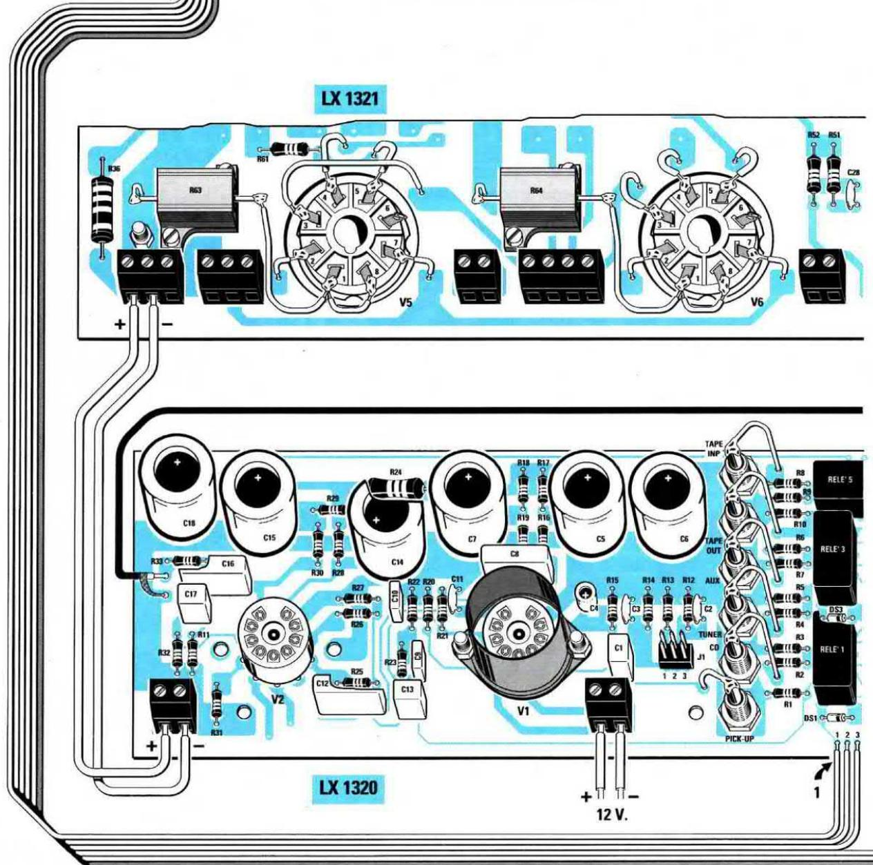
Fig.9 Per tarare i trimmer R4-R6-R8-R10 presenti nello stadio di alimentazione, dovreste collegare un tester ai capi delle resistenze R63-R64 dei due canali, ruotando poi i trimmer in modo da leggere una tensione di 1,25 volt. Questi trimmer possono essere tarati anche senza utilizzare alcun tester, ma semplicemente ruotandoli fino a quando tutti i diodi led bicolore DL1-DL2 si accenderanno sul colore "giallo".
