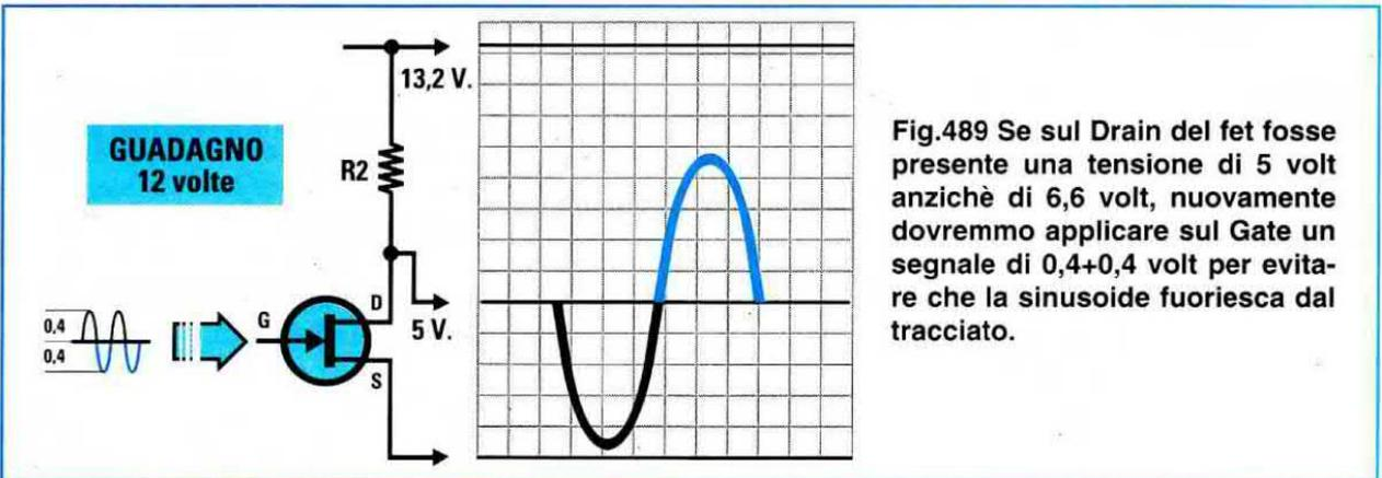
Fig.489 Se sul Drain del fet fosse presente una tensione di 5 volt anzichè di 6,6 volt, nuovamente dovremmo applicare sul Gate un segnale di 0,4+0,4 volt per evitare che la sinusoide fuoriesca dal tracciato.
