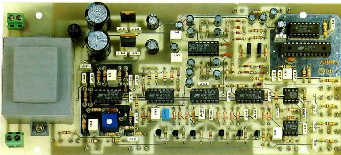
Fig.5 Ecco come si presenterà la scheda LX.1315 una volta che avrete montato tutti i suoi componenti. Nel montaggio dovrete rispettare la polarità dei diodi al silicio, perchè se rivolgerete la loro fascia "nera" in senso inverso rispetto a quanto indicato nel disegno pratico di fig.4 il circuito non potrà funzionare. Lo stesso dicasi per i condensatori elettrolitici e per la tacca di riferimento a forma di U presente sul corpo degli integrati.
