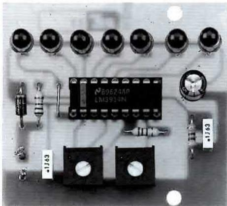
**Fig.4** Foto del circuito stampato riprodotto a grandezza naturale, con sopra montati tutti i diodi led e gli altri componenti.
