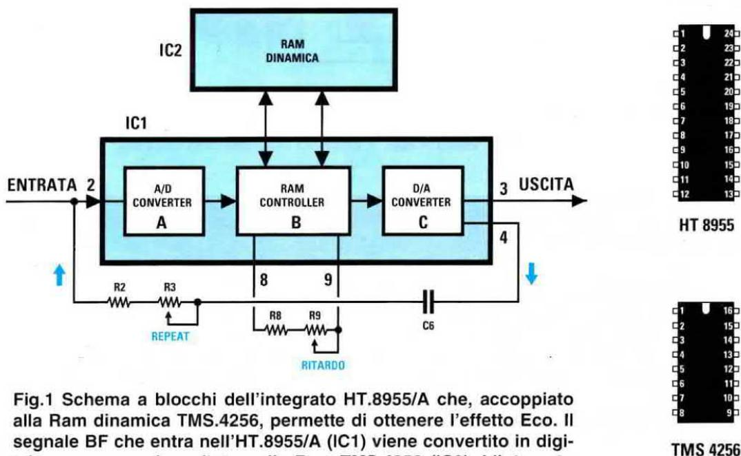
Fig.1 Schema a blocchi dell'integrato HT.8955/A che, accoppiato alla Ram dinamica TMS.4256, permette di ottenere l'effetto Eco. Il segnale BF che entra nell'HT.8955/A (IC1) viene convertito in digitale per essere depositato nella Ram TMS.4256 (IC2). L'integrato IC1 lo preleva da IC2 con un ritardo variabile da 5 a 100 millisecondi (vedi R9), poi lo riconverte da digitale ad analogico e miscela il segnale ritardato al segnale del microfono.
