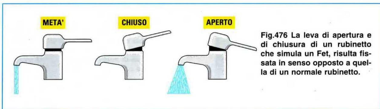
Fig.476 La leva di apertura e di chiusura di un rubinetto che simula un Fet, risulta fissata in senso opposto a quella di un normale rubinetto.
