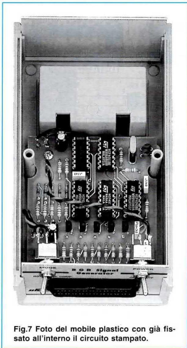
Fig.7 Foto del mobile plastico con già fissato all'interno il circuito stampato.
