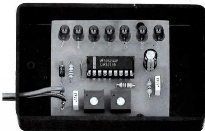
**Fig.5** Prima di inserire il circuito stampato nel mobile, dovrete forare quest'ultimo per far fuoriuscire le teste dei diodi led e i due fili da collegare all'accendisigari.
