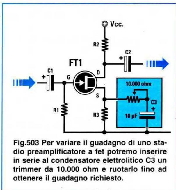
**Fig.503** Per variare il guadagno di uno stadio preamplificatore a fet potremo inserire in serie al condensatore elettrolitico C3 un trimmer da 10.000 ohm e ruotarlo fino ad ottenere il guadagno richiesto.
