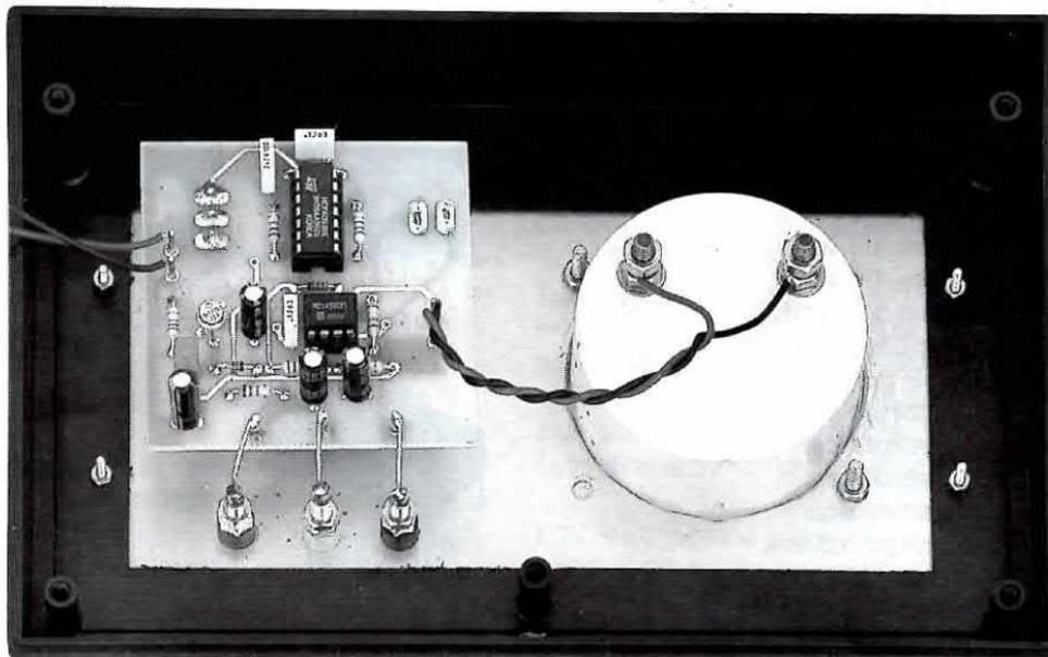
**Fig.516** Il circuito stampato andrà fissato direttamente sul pannello frontale del mobile tramite i dadi del pulsante P1 e dell'interruttore S1 (vedi fig.522). Sul lato destro del pannello troverà posto lo strumento voltmetro da 5 volt fondo scala.
