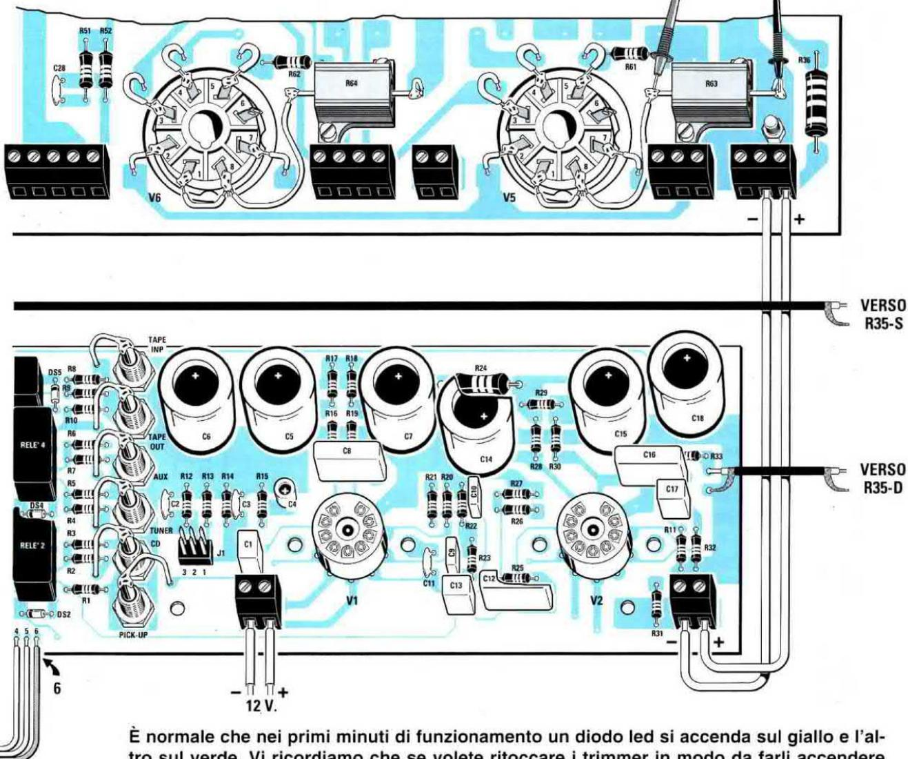
È normale che nei primi minuti di funzionamento un diodo led si accenda sul giallo e l'altro sul verde. Vi ricordiamo che se volete ritoccare i trimmer in modo da farli accendere tutti sul giallo, questa operazione va eseguita dopo 5 minuti di funzionamento. I cavetti schermati visibili a destra vanno collegati ai potenziometri R35/S-R35/D (vedi fig.14).
