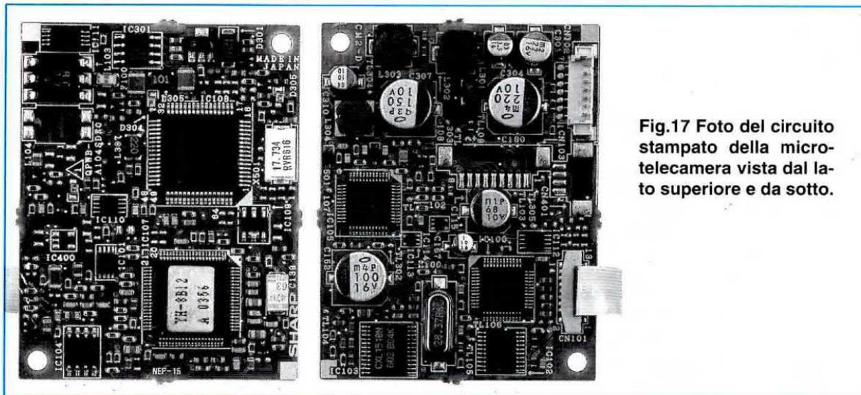
Fig.17 Foto del circuito stampato della microtelecamera vista dal lato superiore e da sotto.
