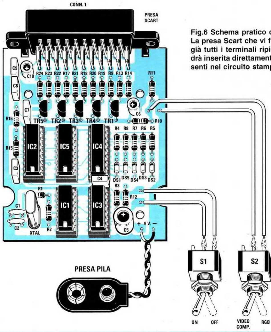
Fig.6 Schema pratico di montaggio. La presa Scart che vi forniremo con già tutti i terminali ripiegati a L, andrà inserita direttamente nei fori presenti nel circuito stampato.
