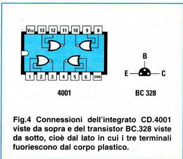
**Fig.4 Connessioni dell'integrato CD.4001 viste da sopra e del transistor BC.328 viste da sotto, cioè dal lato in cui i tre terminali fuoriescono dal corpo plastico.**
