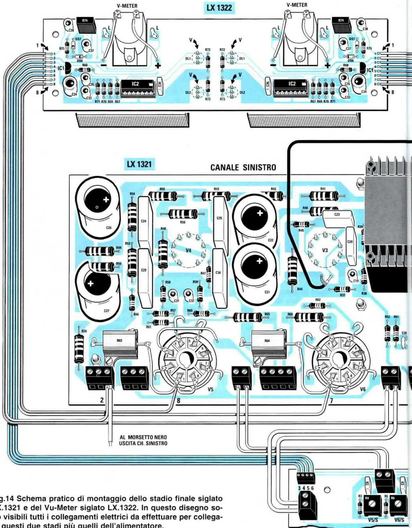
Fig.14 Schema pratico di montaggio dello stadio finale siglato LX.1321 e del Vu-Meter siglato LX.1322. In questo disegno sono visibili tutti i collegamenti elettrici da effettuare per collegare questi due stadi più quelli dell'alimentatore.
