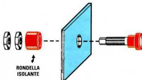
**Fig.522** Il circuito stampato andrà fissato sulla mascherina con il dado del pulsante P1 e con il dado dell'interruttore S1.
