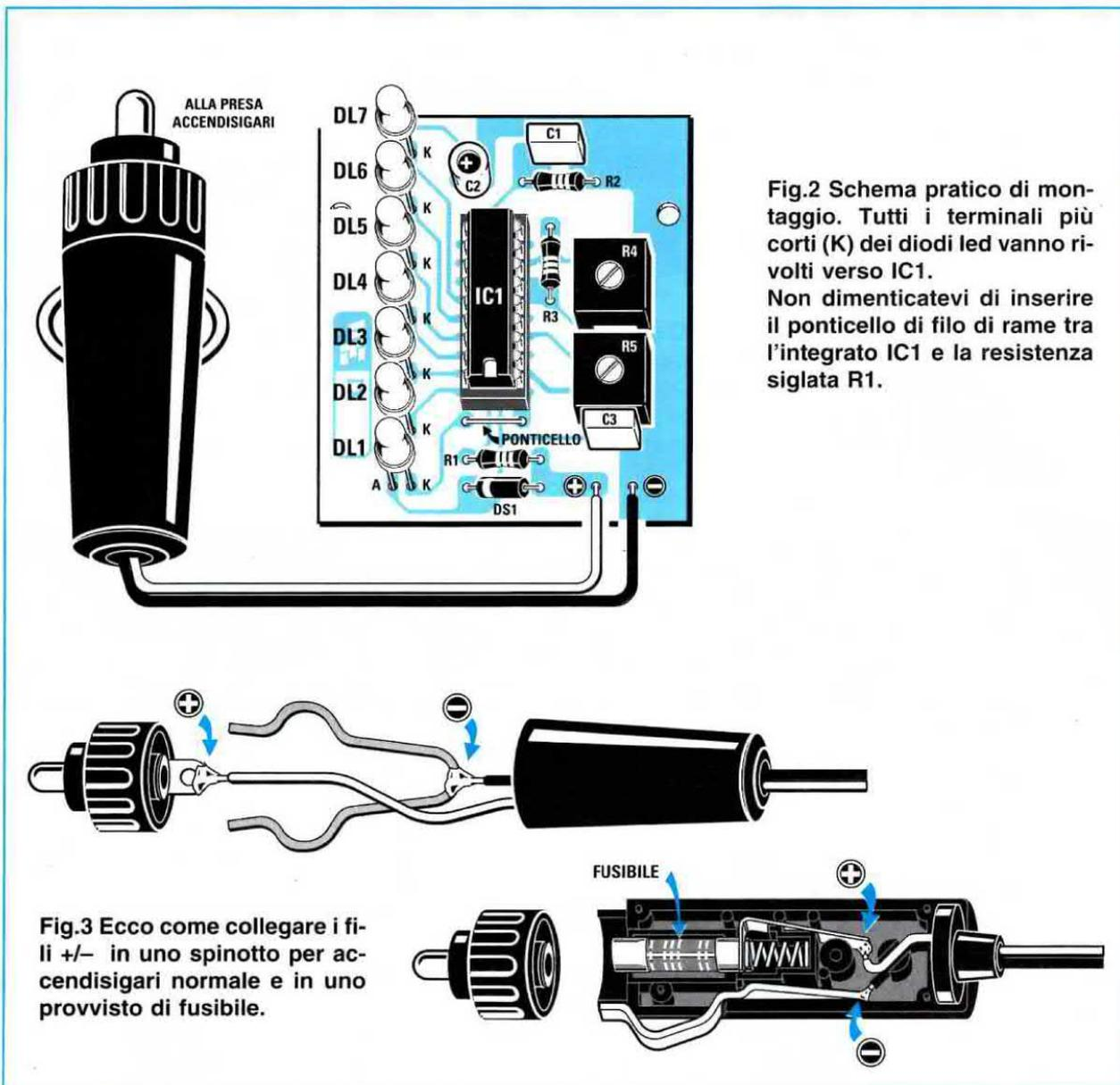
Fig.2 Schema pratico di montaggio. Tutti i terminali più corti (K) dei diodi led vanno rivolti verso IC1. Non dimenticatevi di inserire il ponticello di filo di rame tra l'integrato IC1 e la resistenza siglata R1.
