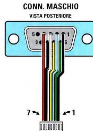
Fig.12 I fili che fuoriescono dal connettore dello stampato della telecamera, numerati da 1 a 7, vanno collegati ai terminali del connettore maschio a 9 poli come qui sotto indicato:
