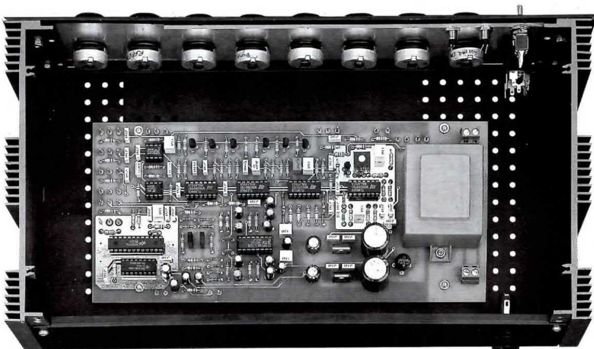
Fig.2 Foto dell'interno del mobile contenente il circuito stampato e tutti i potenziometri. Vi ricordiamo che il potenziometro logaritmico R50 del Master è siglato 470KB, quindi non dovete confonderlo con il potenziometro lineare R61 del Delay siglato 470KA.
