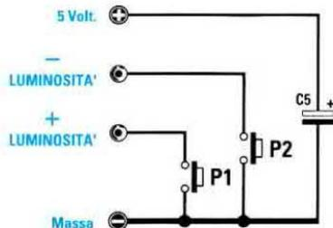
Fig.14 Schema elettrico del circuito che serve per variare la luminosità.
