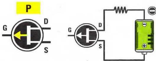
Fig.472 I Fet di canale P si riconoscono perchè la linea che parte dal terminale Gate ha una freccia rivolta verso l'esterno. In questi Fet il terminale Drain va collegato al Negativo di alimentazione e il terminale Source va collegato al Positivo.
