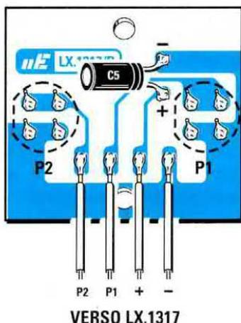
Fig.20 Prima di fissare i due pulsanti sullo stampato LX.1317/B, controllate se i contatti sono disposti come visibile in figura.
