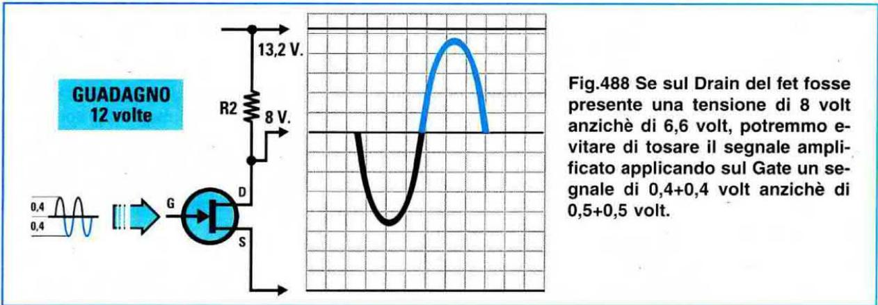
Fig.488 Se sul Drain del fet fosse presente una tensione di 8 volt anzichè di 6,6 volt, potremmo evitare di tosare il segnale amplificato applicando sul Gate un segnale di 0,4+0,4 volt anzichè di 0,5+0,5 volt.
