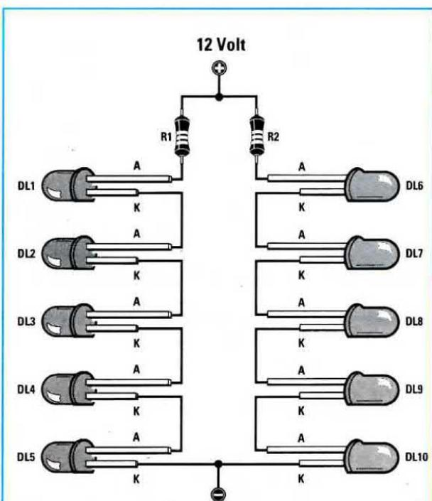
**Fig.18** Collegando 10 diodi emittenti a raggi infrarossi potrete vedere al buio, ma **NON** a colori. Per alimentare questi diodi vengono utilizzati i 12 volt forniti dallo stadio di alimentazione. Per R1-R2 dovrete usare due resistenze da 120 ohm 1/4 watt.
