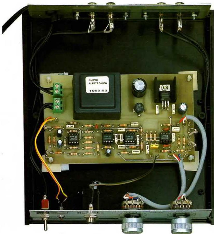
Fig.4 In questa foto potete vedere come andrà a cato il circuito stampato all'interno del suo involucro in plastica.
