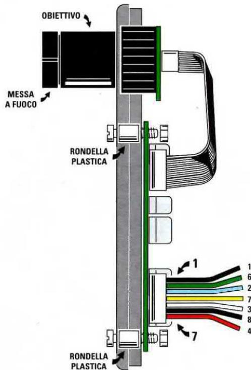
Fig.11 Per tenere il circuito stampato della telecamera distanziato dal mobile MTV03 si devono utilizzare le due piccole rondelle in plastica contenute nel mobile insieme ai due connettori a 9 poli. Nel disegno abbiamo colorato i sette fili anche se nella piattina che troverete nel kit risultano tutti di colore grigio.
