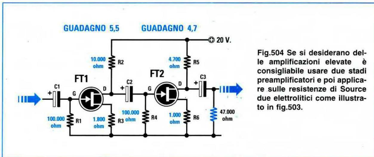
Fig.504 Se si desiderano delle amplificazioni elevate è consigliabile usare due stadi preamplificatori e poi applicare sulle resistenze di Source due elettrolitici come illustrato in fig.503.
