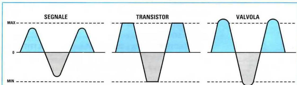
Fig.1 Il suono emesso da un finale a transistor risulta identico a quello di un finale a valvole, fino a quando l'ampiezza del segnale non supera il suo picco massimo. Superato questo picco, i transistor tosano brutalmente le estremità delle onde sinusoidali che, trasformandosi in trapezoidali, generano molte armoniche dispari, mentre le valvole, appiattendole leggermente senza tosarle, generano solo armoniche pari.
