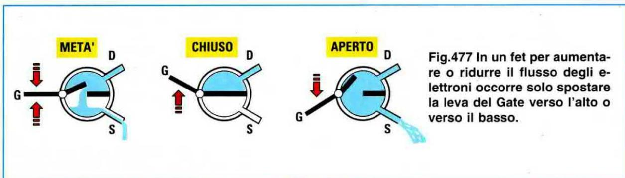
Fig.477 In un fet per aumentare o ridurre il flusso degli elettroni occorre solo spostare la leva del Gate verso l'alto o verso il basso.
