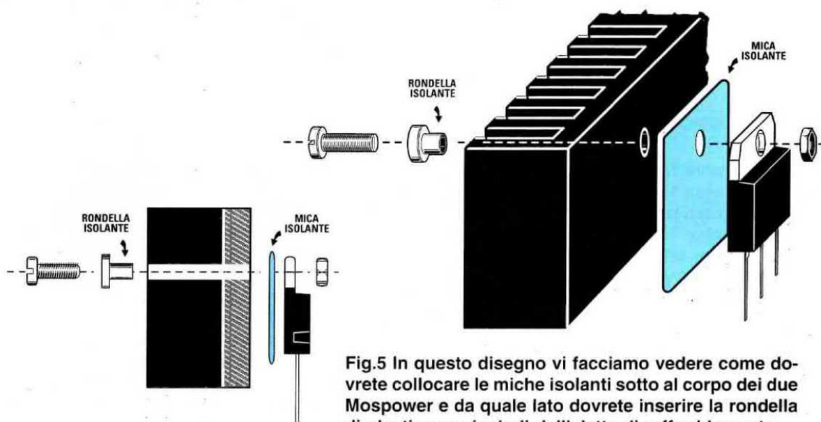
Fig.5 In questo disegno vi facciamo vedere come dovrete collocare le miche isolanti sotto al corpo dei due Mospower e da quale lato dovrete inserire la rondella di plastica per isolarli dall'aletta di raffreddamento.
