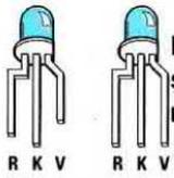
Fig.13 Il terminale Rosso dei diodi bicolore è ripiegato a L capovolta.
