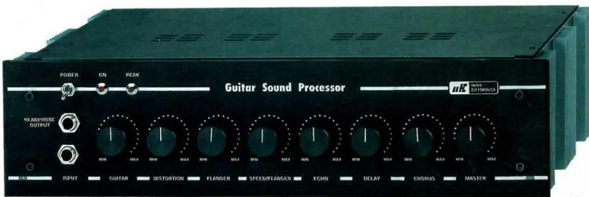
Questo circuito professionale provvede a generare tutti i principali effetti speciali che un chitarrista desidera ottenere dalla propria chitarra elettrica, cioè un suono Distorto simile a quello che si ottiene con le valvole termoioniche, un effetto Flanger, un effetto Echo con l'aggiunta di un Chorus che dà la sensazione che a suonare siano più chitarre insieme.
