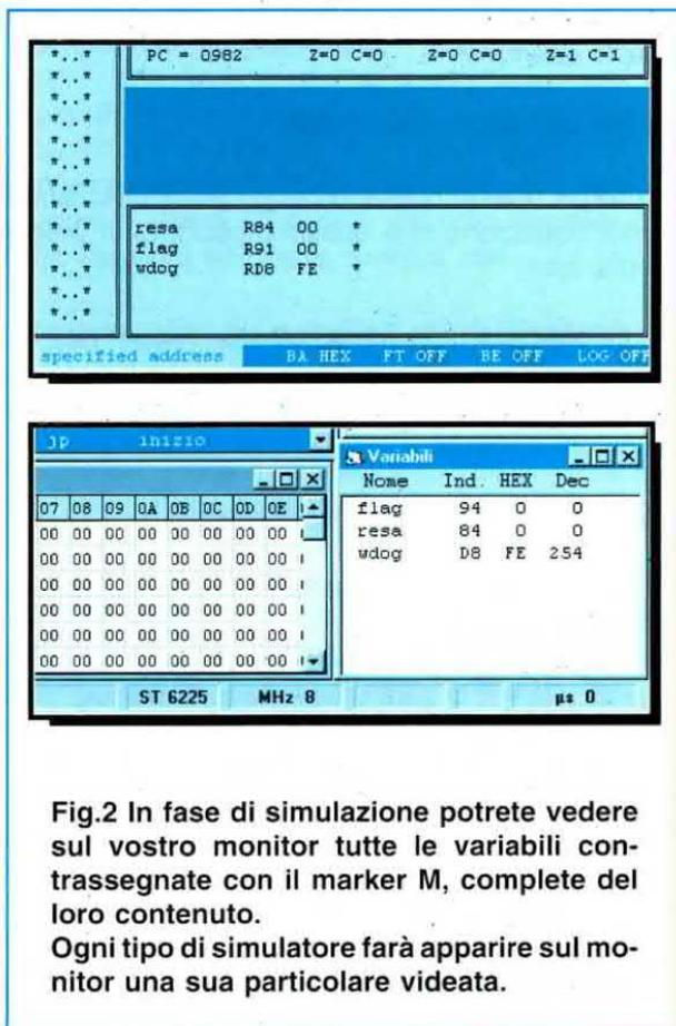
**Fig.2** In fase di simulazione potrete vedere sul vostro monitor tutte le variabili contrassegnate con il marker M, complete del loro contenuto.
