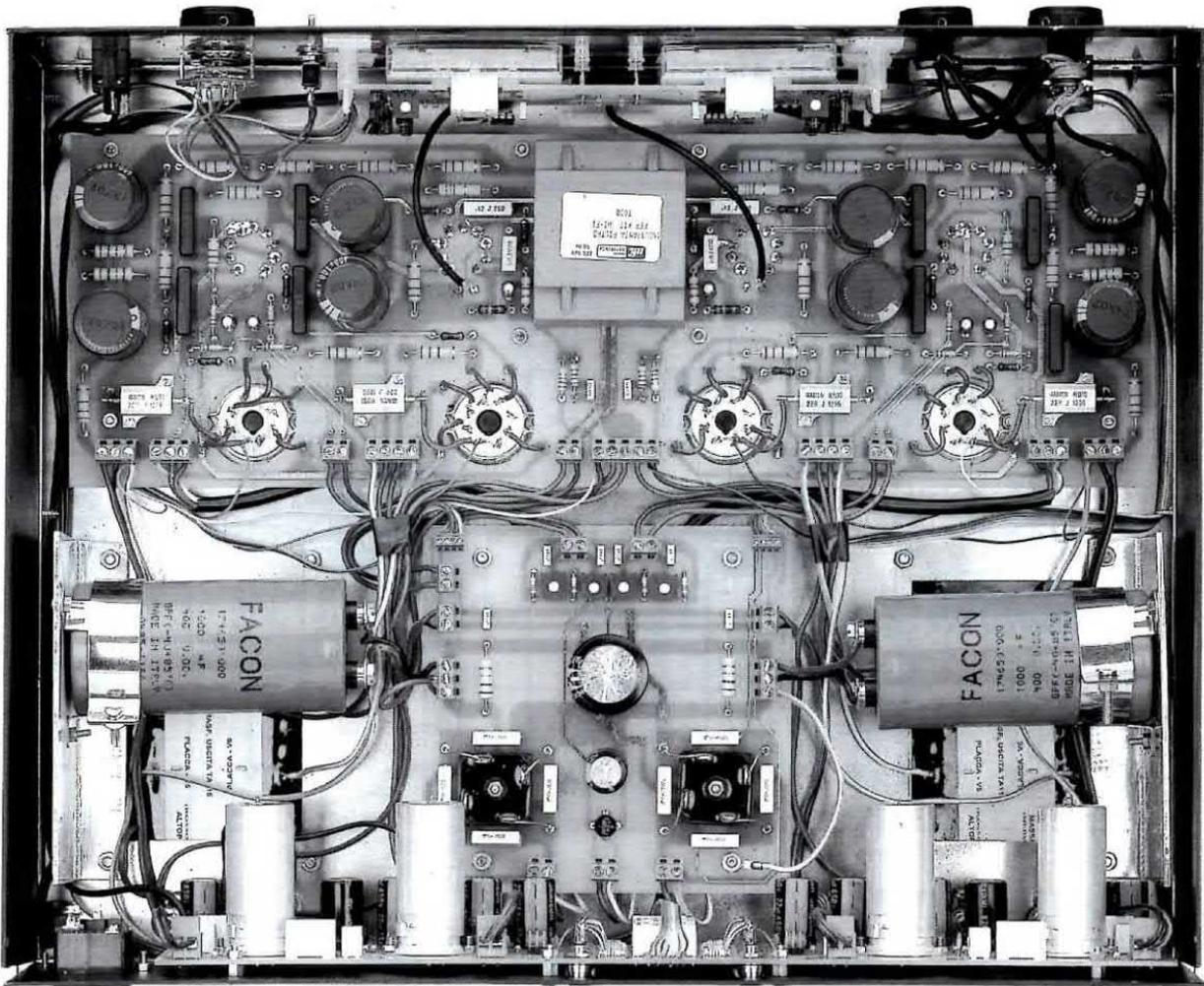
Fig.2 Foto dell'interno del mobile. Nei disegni di figg.8-14-15-18 sono visibili i collegamenti elettrici da effettuare sulle quattro schede LX.1320-LX.1321-LX.1322-LX.1323. I due grossi condensatori elettrolitici C5-C6 dello stadio di alimentazione andranno collocati sopra alle due squadrette a L che dovete fissare sulle viti dei due trasformatori d'uscita.
