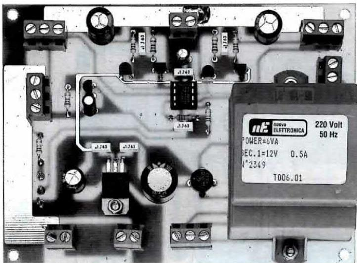
Fig.7 Come si presenta il circuito stampato di questo Carico con sopra montati tutti i suoi componenti.
