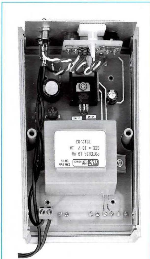
Fig.19 Foto dell'alimentatore racchiuso all'interno del relativo mobile plastico.
