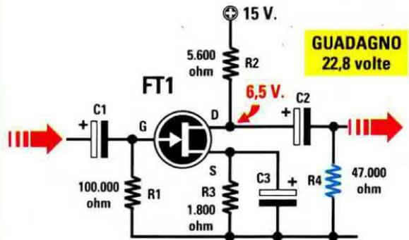
Fig.498 Se in parallelo alla resistenza **R3** applicheremo un condensatore elettrolitico (vedi nello schema **C3**) il guadagno da **3,11 volte** salirà a **22,8 volte**.
