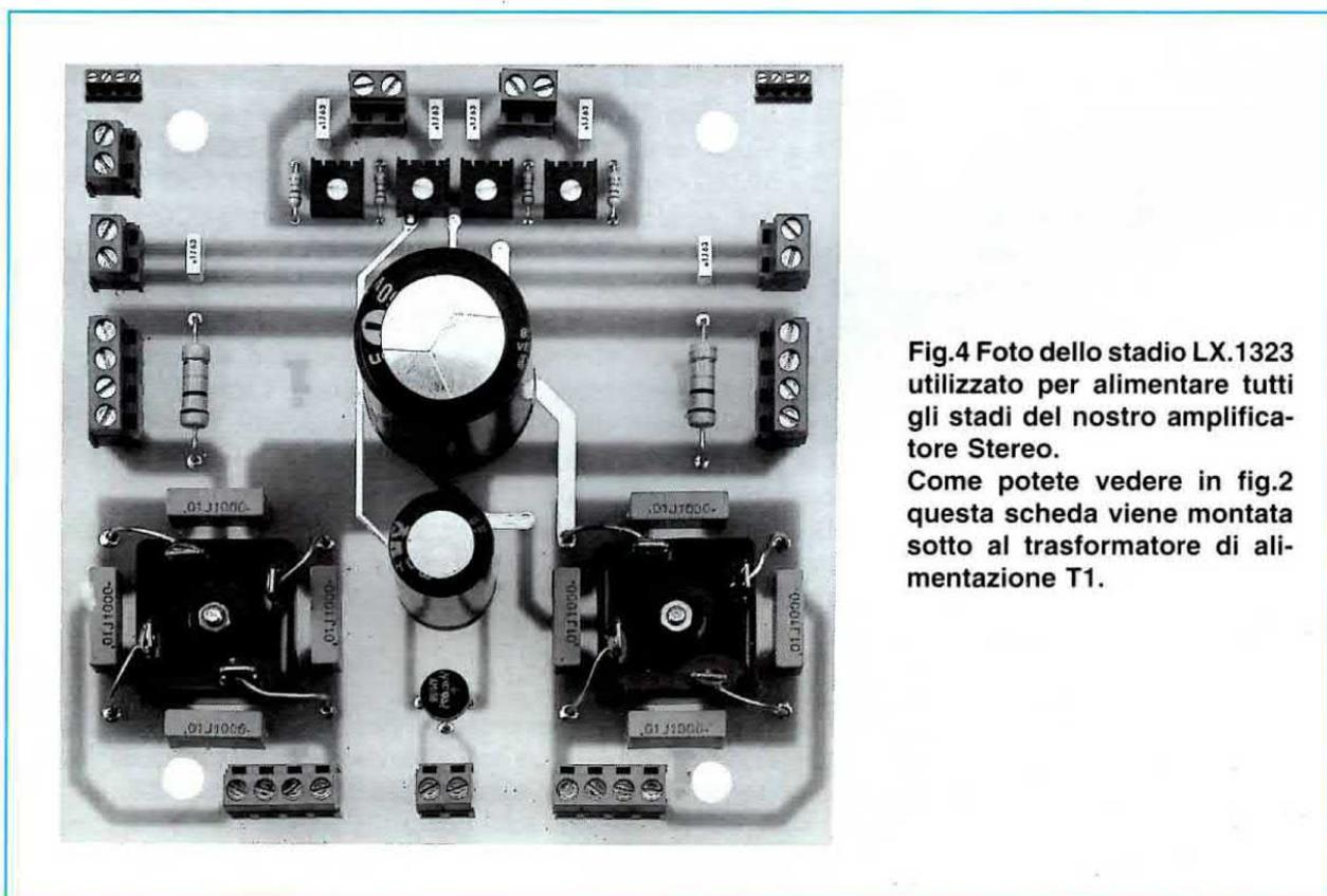
**Fig.4** Foto dello stadio LX.1323 utilizzato per alimentare tutti gli stadi del nostro amplificatore Stereo. Come potete vedere in fig.2 questa scheda viene montata sotto al trasformatore di alimentazione T1.
