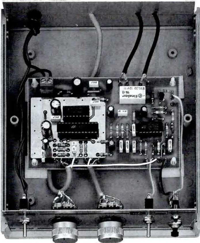
**Fig.6** Il circuito stampato andrà racchiuso entro un piccolo ed elegante mobile plastico. Sul pannello frontale fisserete i due potenziometri del Ritardo e del Repeat, il pulsante P1, i due interruttori S1-S2 ed il diodo led DL1.
