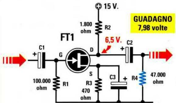
Fig.499 Per realizzare uno stadio in grado di amplificare dei segnali di ampiezza elevata sarà sufficiente ridurre il valore delle due sole resistenze **R2-R3**.
