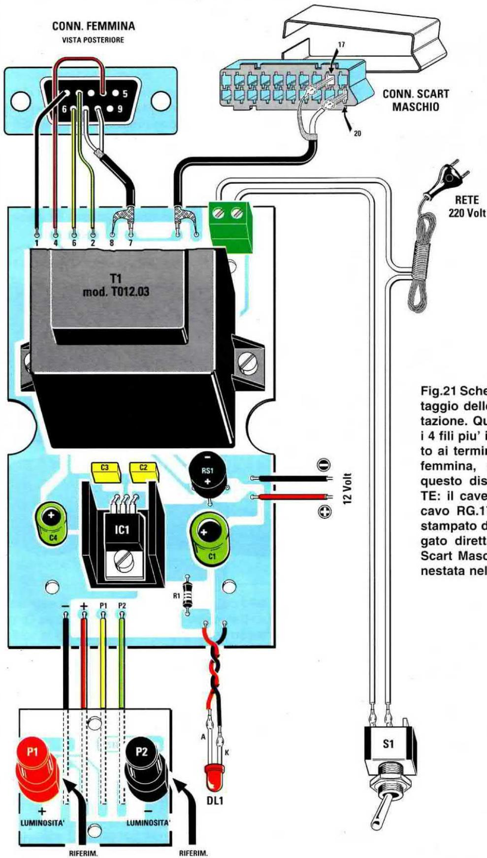
Fig.21 Schema pratico di montaggio dello stadio di alimentazione. Quando collegherete i 4 fili piu' il cavetto schermato ai terminali del connettore femmina, dovrete rispettare questo disegno. **IMPORTANTE:** il cavetto schermato o il cavo RG.174 che esce dallo stampato dovra' essere collegato direttamente alla presa Scart Maschio che andra' innestata nel televisore.
