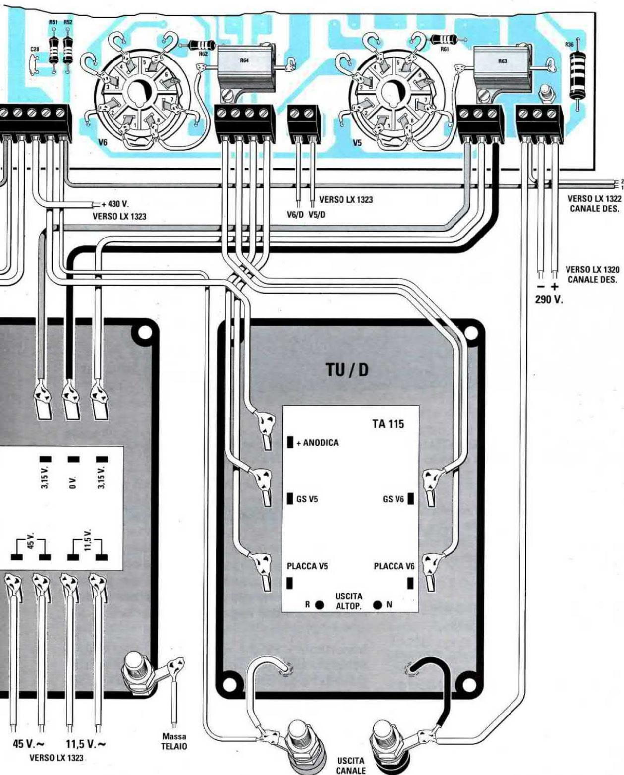
Fig.18 In questo disegno potete vedere come collegare tutti i terminali dei due trasformatori d'uscita e quello di alimentazione alle morsettiere presenti sul circuito stampato dello stadio finale siglato LX.1321. La presa "massa telaio" presente sul bullone del trasformatore di alimentazione va collegata alla morsettiere posta sul lato destro dello stampato LX.1323 (vedi fig.15) e anche al filo Terra della presa rete 220 volt.
