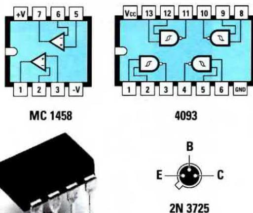
Fig.515 Connessioni viste da sopra dei due integrati MC.1458 e CD.4093 e del transistor 2N.3725 viste invece da sotto. Si noti sul lato sinistro dei due integrati la tacca di riferimento a forma di U e nel transistor la piccola sporgenza metallica.
