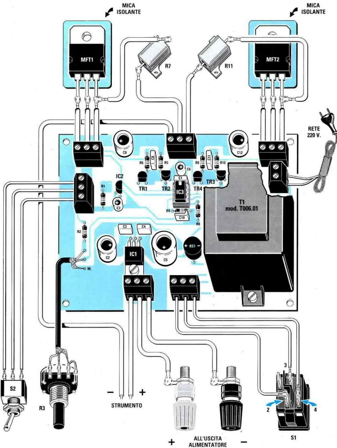
Fig.6 Schema pratico di montaggio del Carico Attivo. Prima di fissare le due boccole a morsetto sul pannello frontale, dovrete togliere dalla loro parte posteriore la rondella di plastica inserita all'interno del pannello per isolarle dal metallo.
