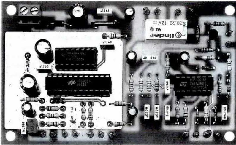
**Fig.5** Foto del circuito stampato LX.1312 con sopra montati tutti i suoi componenti. Per evitare che lo stadio IC1-IC2 irradi dei disturbi, tutte le sue piste risultano schermate da una larga pista in rame collegata alla massa di alimentazione.
