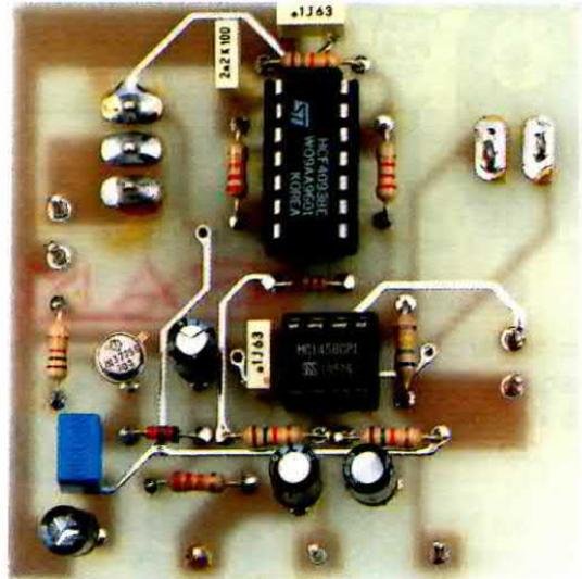
**Fig.519** Una volta inseriti tutti i componenti nella basetta del circuito stampato questa si presenterà come nella foto. Nei fori ai quali andranno collegati i fili dei componenti esterni dovete inserire i piccoli terminali a spillo presenti nel kit.
