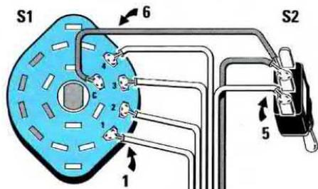
Fig.8 Schema pratico di montaggio dello stadio preamplificatore LX.1320 compresi i collegamenti che dovrete effettuare per collegarvi con lo stampato LX.1321, con il commutatore rotativo S1 e con quello a levetta S2. Nel collegare questi fili dovrete cercare di non invertirli, in particolare dovrete fare attenzione a quelli di alimentazione se volete evitare dei cortocircuiti. Se eseguirete delle saldature perfette il circuito funzionerà non appena completato l'assemblaggio.
