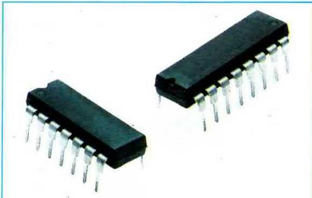
**Fig.592** Le porte digitali sono sempre racchiuse dentro un integrato provvisto di 14 o di 16 piedini. Su un solo lato di questi corpi è presente una tacca di riferimento a forma di U che ci permette di individuare il piedino 1 (vedi figg.594-595).
