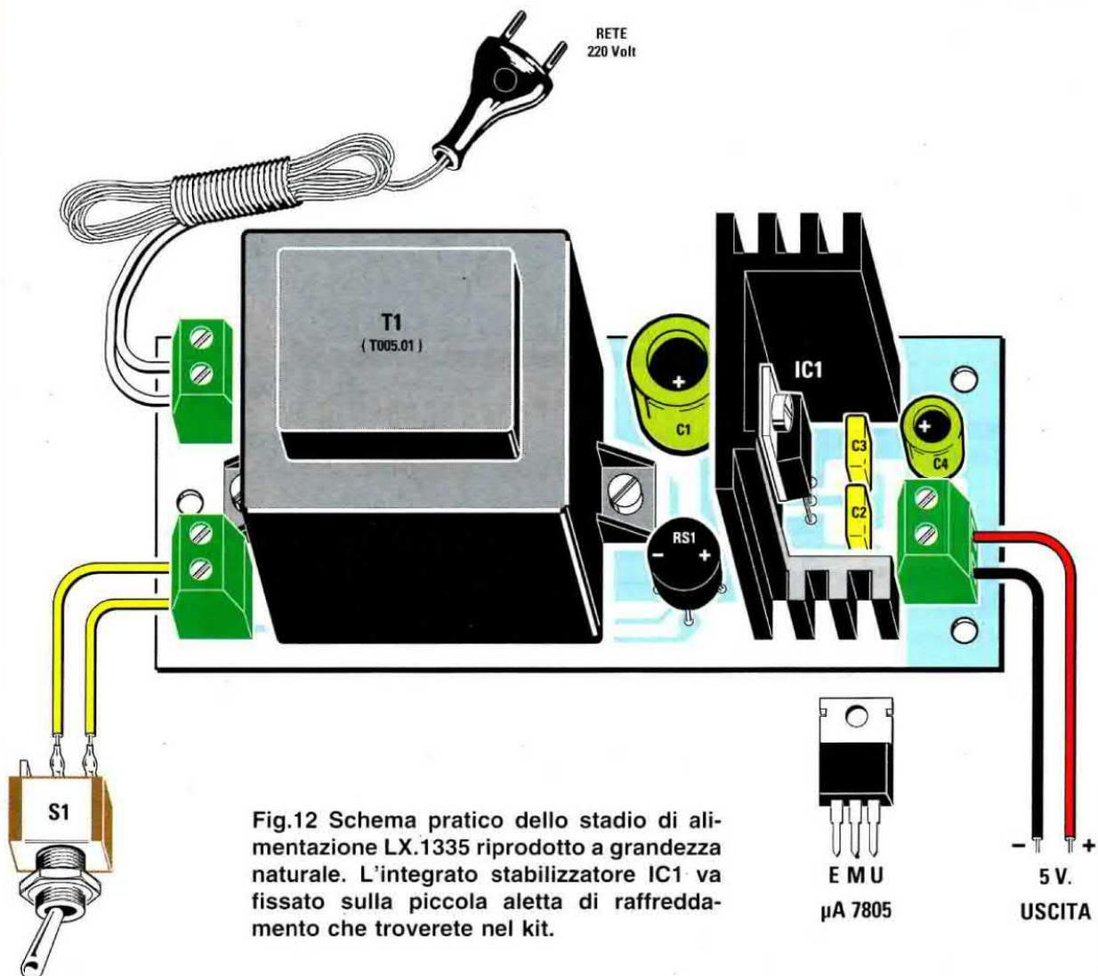
Fig.12 Schema pratico dello stadio di alimentazione LX.1335 riprodotto a grandezza naturale. L'integrato stabilizzatore IC1 va fissato sulla piccola aletta di raffreddamento che troverete nel kit.
