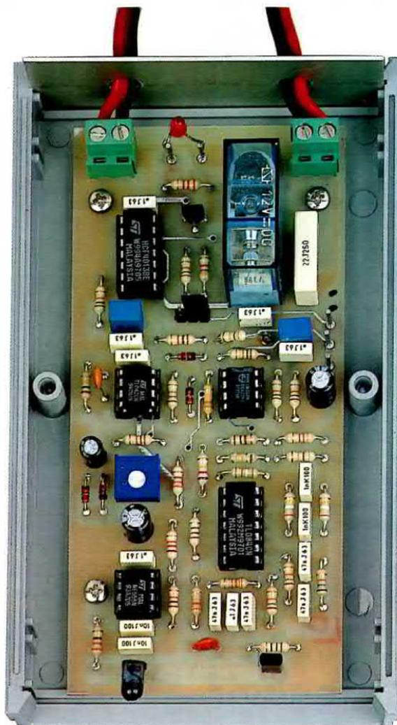
**Fig.5** Il circuito va fissato dentro un piccolo mobile plastico sprovvisto di pannello frontale per poter far uscire e rientrare il raggio riflesso all'infrarosso. Il diodo trasmittente DTX e quello ricevente DRX possono essere collegati anche ad una distanza non superiore a 1 metro dal circuito stampato, utilizzando due spezzoni di sottile cavo coassiale tipo RG.174 come visibile in fig.10.
