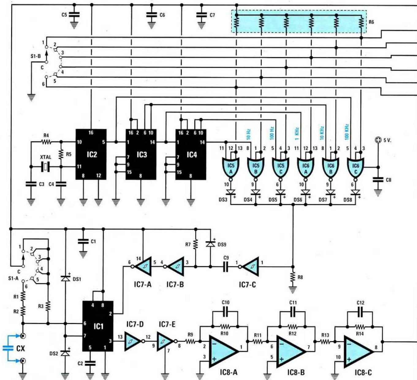
Fig.6 Schema elettrico del capacimetro siglato LX.1340. La lista dei componenti si trova nella pagina successiva, quella dello stadio di alimentazione duale in fig.8. I ponticelli J1 - J2 servono per tarare il capacimetro come spiegato a fine articolo.
