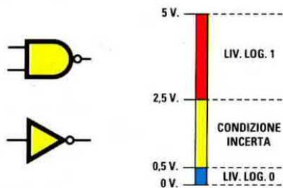
Fig. 586 Tutti i piedini d'ingresso di una normale Porta riconoscono un Livello logico 1 quando la tensione supera i 2,5 volt ed un Livello logico 0 quando scende sotto i 0,5 volt. Tutti i valori di tensione intermedi sono condizioni incerte.
