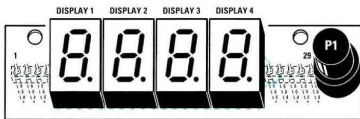
Fig.11 Quando inserite i quattro display nello stampato LX.1340/D rivolgete il punto decimale verso il basso.
