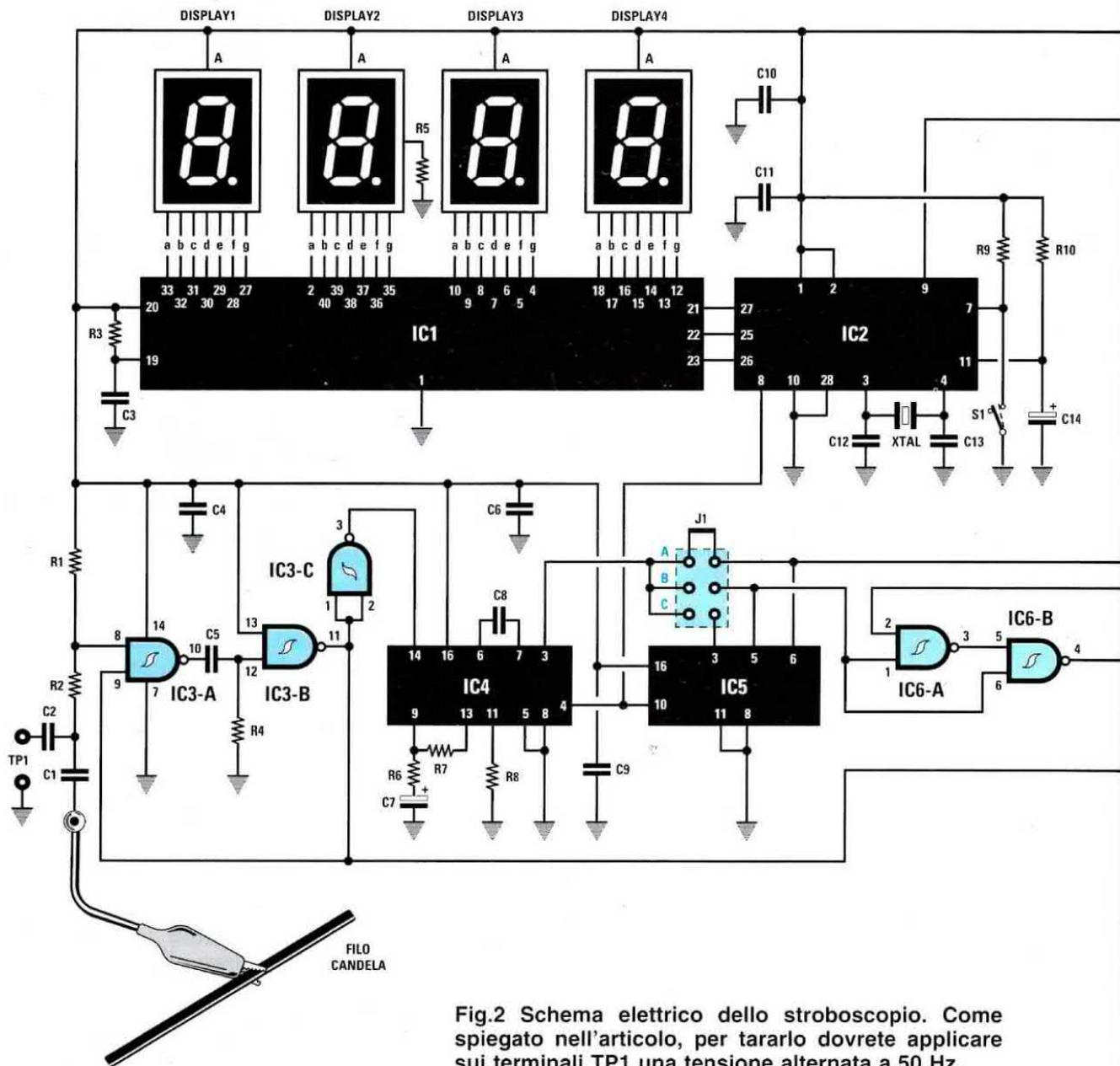
Fig.2 Schema elettrico dello stroboscopio. Come spiegato nell'articolo, per tararlo dovrete applicare sui terminali TP1 una tensione alternata a 50 Hz.
