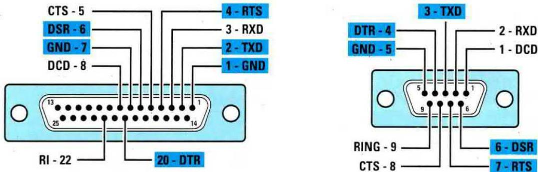
Fig.12 Se la presa ingresso seriale del vostro computer ha 25 poli dovreste procurarvi un cavo seriale provvisto di un connettore maschio/femmina a 25 poli. Se invece ha una presa a 9 poli dovreste procurarvi un cavo seriale provvisto di un connettore maschio a 25 poli e un connettore femmina a 9 poli. Nel disegno indichiamo dove dovranno entrare i segnali GND-DSR-RTS-TXD-DTR sia nel connettore seriale a 25 poli che in quello a 9 poli.
