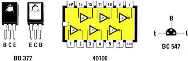
Fig.611 Connessioni dei transistor BD.377-BC.547 e dell'integrato 40106.
