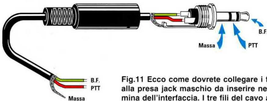
Fig.11 Ecco come dovreste collegare i fili BF-PTT Massa alla presa jack maschio da inserire nel connettore femmina dell'interfaccia. I tre fili del cavo andranno poi collegati alla presa BF-PTT del ricetrasmittente.
