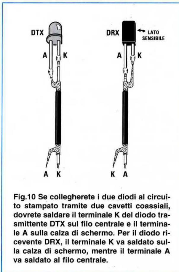
**Fig.10** Se collegherete i due diodi al circuito stampato tramite due cavetti coassiali, dovrete saldare il terminale **K** del diodo trasmettente **DTX** sul filo centrale e il terminale **A** sulla calza di schermo. Per il diodo ricevente **DRX**, il terminale **K** va saldato sulla calza di schermo, mentre il terminale **A** va saldato al filo centrale.
