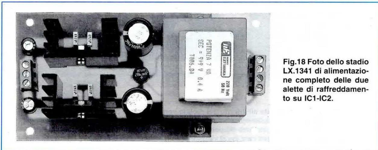
Fig.18 Foto dello stadio LX.1341 di alimentazione completo delle due alette di raffreddamento su IC1-IC2.
