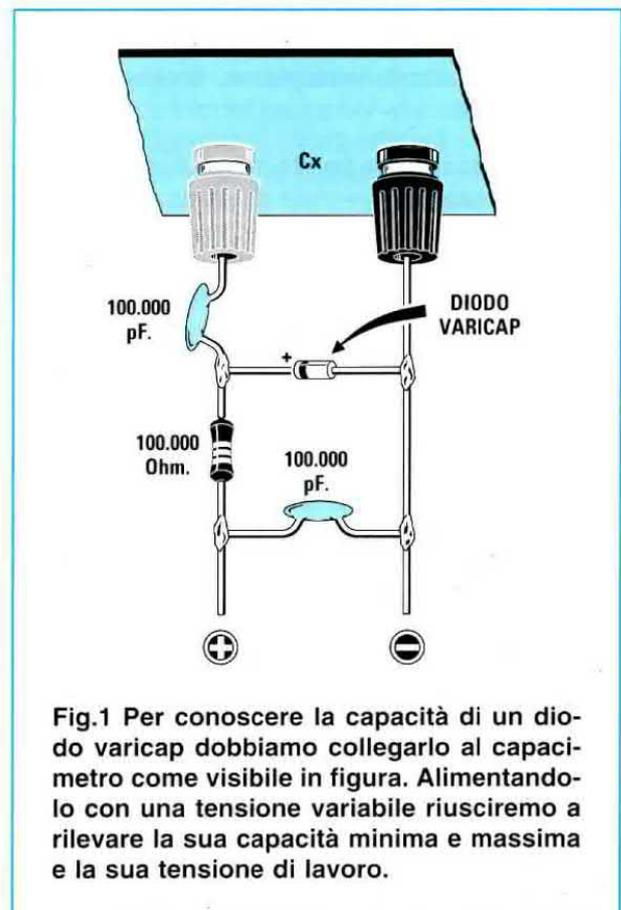
Fig.1 Per conoscere la capacità di un diodo varicap dobbiamo collegarlo al capacimetro come visibile in figura. Alimentandolo con una tensione variabile riusciremo a rilevare la sua capacità minima e massima e la sua tensione di lavoro.
