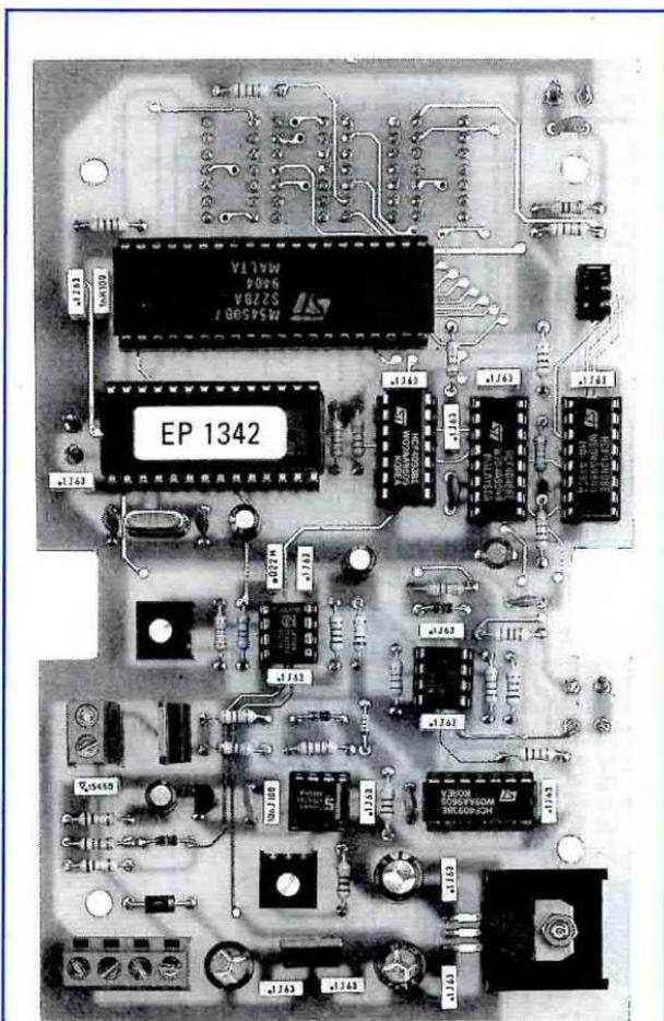
Fig.3 Foto della scheda LX.1342 come si presenta dopo aver montato tutti i componenti. Vedi schema pratico di fig.5.
