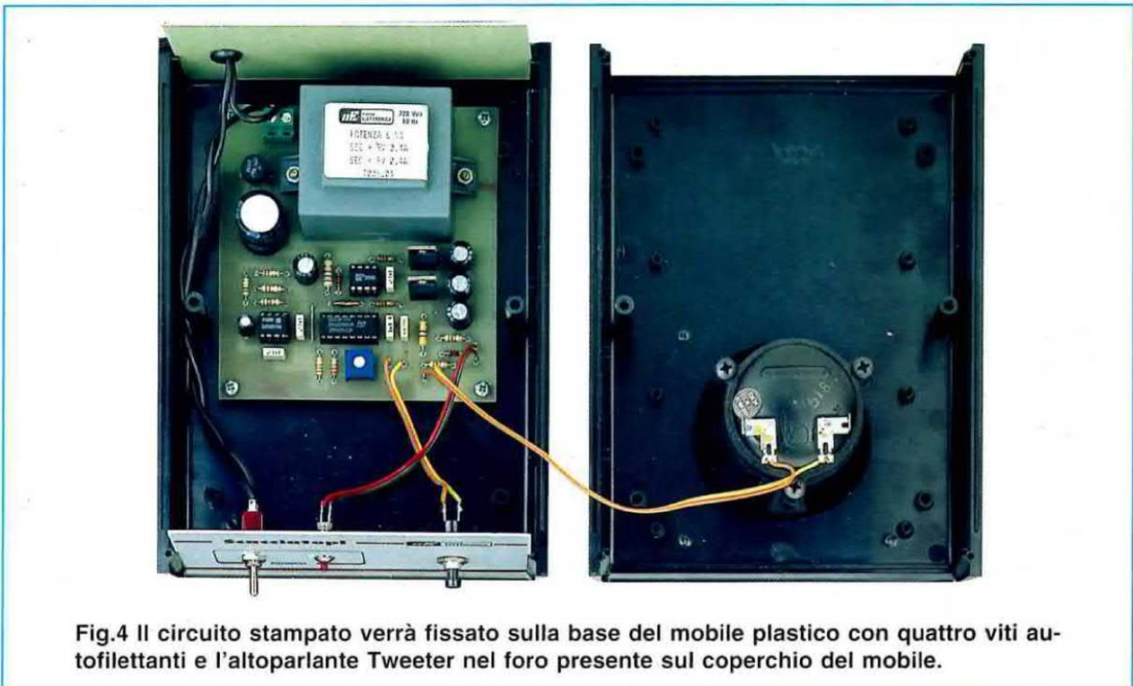
Fig.4 Il circuito stampato verrà fissato sulla base del mobile plastico con quattro viti autofilettanti e l'altoparlante Tweeter nel foro presente sul coperchio del mobile.
