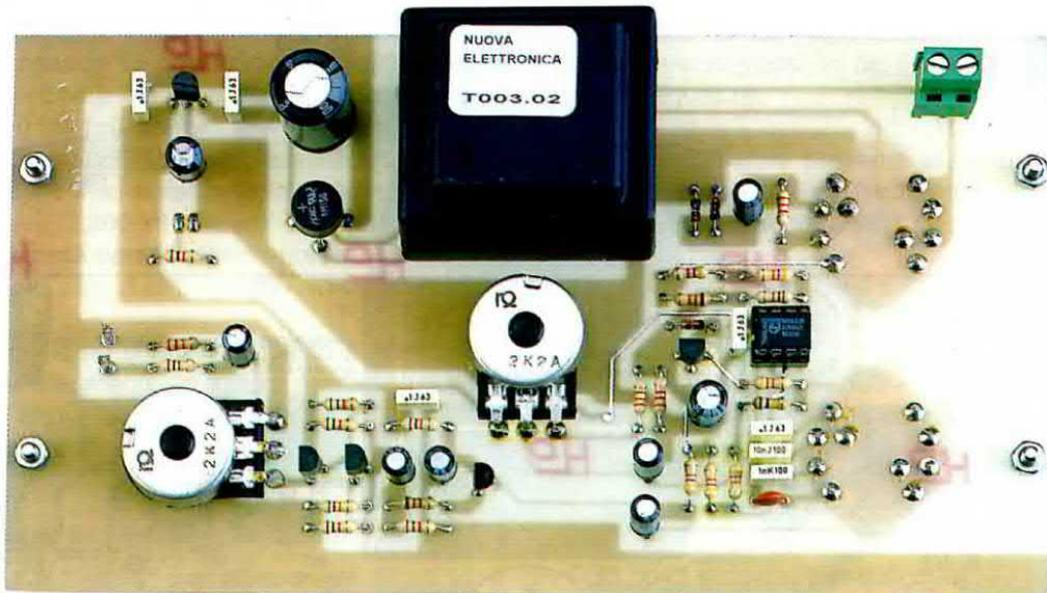
**Fig.8** Foto del circuito stampato visto dal lato dei componenti. Poichè questa foto è stata eseguita su uno degli esemplari usati per il collaudo, manca ancora il disegno serigrafico che risulterà invece presente su tutti i circuiti stampati di produzione forniti nei kits.
