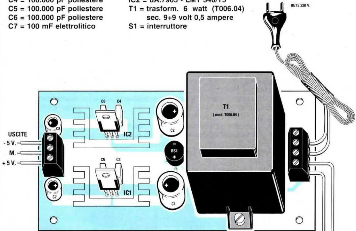
Fig.9 Schema pratico dello stadio di alimentazione e connessioni dei due integrati stabilizzatori. L'integrato uA.7905 utilizzato per ottenere la tensione stabilizzata dei 5 volt negativi può essere sostituito dall'equivalente LMT.340/T5. Il lato metallico di questi due integrati va rivolto in basso e fissato sopra l'aletta di raffreddamento come visibile in fig.18.
