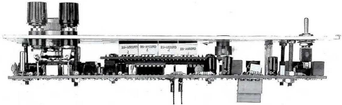
Fig.14 Foto delle due schede LX.1340 - LX.1340/D già fissate sul pannello frontale viste dal lato dei morsetti d'ingresso. Per collegare i terminali dei due morsetti d'ingresso sulle piste del circuito stampato potete utilizzare due corti spezzoni di filo di rame nudo.
