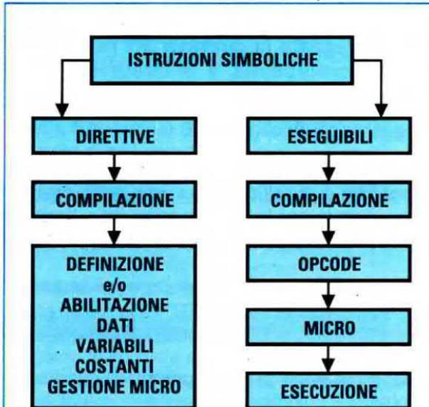
Fig.1 Semplificando possiamo definire le direttive come disposizioni generali atte a fissare le caratteristiche di fondo che necessitano al programma. Ad esempio: definizione di dati, variabili, macro, costanti simboliche, abilitazione dell'area di memoria Data Rom Window, ecc. Perciò, come le istruzioni eseguibili, vengono compilate, ma non generano un oPCODE, cioè un codice operativo eseguibile.
