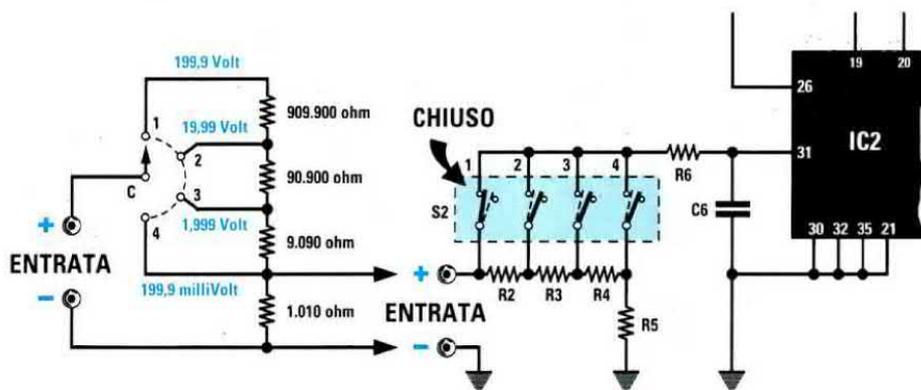
**Fig.16** Se volete utilizzare un commutatore rotativo per commutare le 4 portate, potrete collegarlo direttamente all'ingresso, non dimenticando di commutare il dip-switch S2 sulla portata 200 millivolt (vedi fig.3). Nei terminali del commutatore rotativo dovreste inserire 5 resistenze di precisione del valore indicato nello schema. Tenete questi collegamenti esterni molto corti per evitare di captare dei disturbi.
