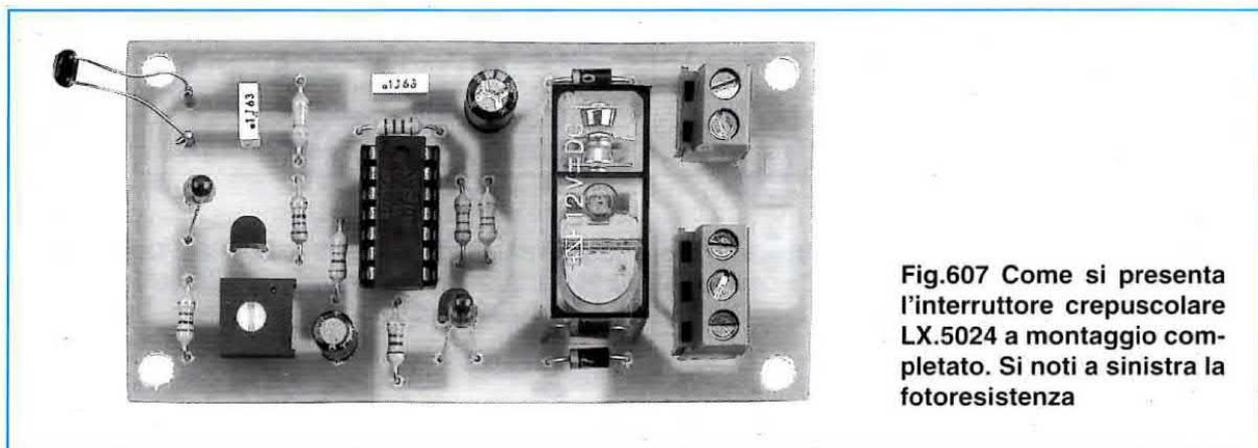
**Fig.607** Come si presenta l'interruttore crepuscolare **LX.5024** a montaggio completo. Si noti a sinistra la **fotoresistenza**
