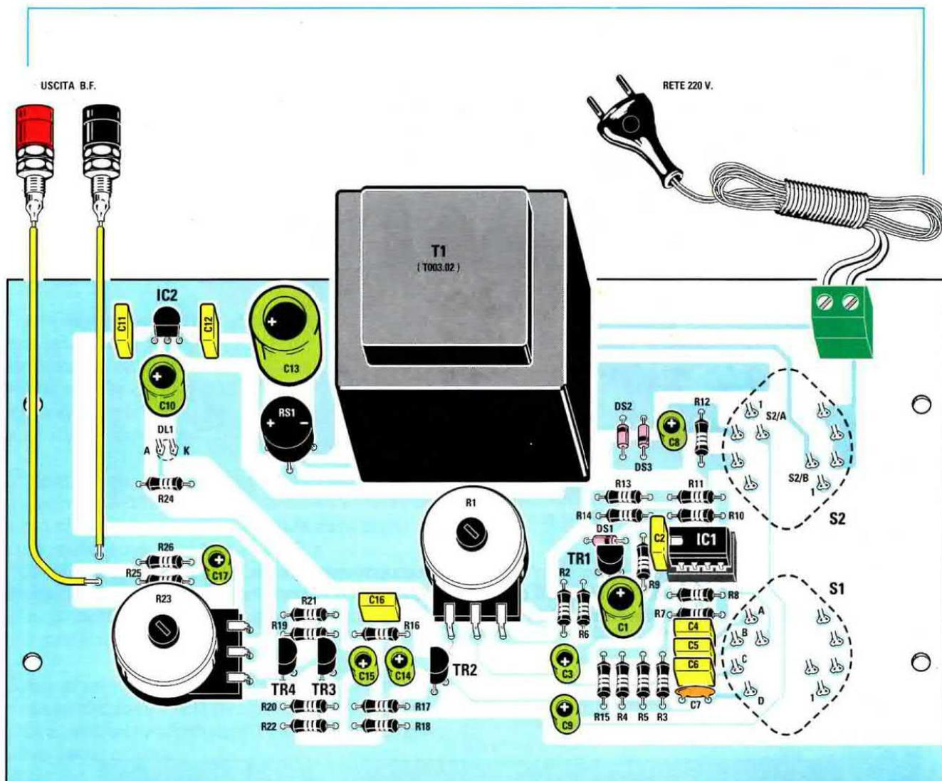
Fig.5 Schema pratico di montaggio del semplice Generatore di BF. Prima di fissare sul circuito stampato i potenziometri e i commutatori rotativi, dovete accorciare i loro perni (vedi figg.6-7) in modo che tutte le manopole siano disposte alla stessa altezza.
