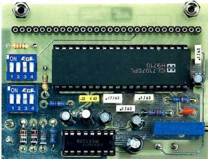
Fig.7 Foto della scheda LX.1334 come si presenta a montaggio ultimato. Nel connettore femmina, posto sopra l'integrato IC2, andrà inserita la scheda dei display visibile in fig.8.
