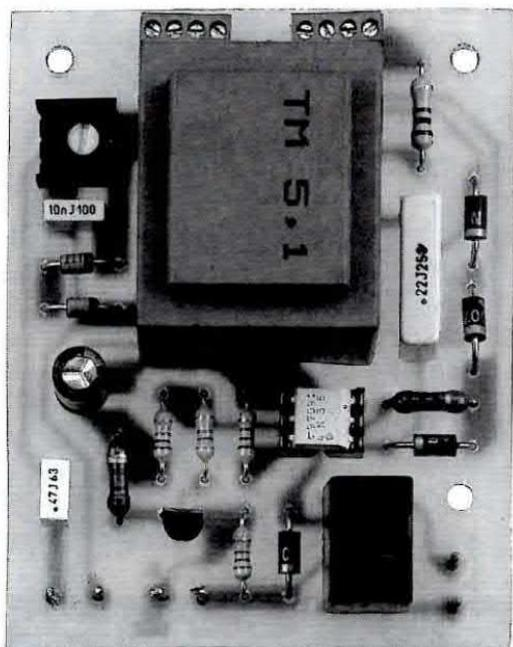
**Fig.4** Ecco come si presenta la basetta del circuito stampato completa di tutti i suoi componenti. Sul circuito stampato riprodotto in questa foto non appare la serigrafia, facendo esso parte della preserie di 10 kits che realizziamo sempre per il collaudo. La serigrafia è invece presente su tutti i circuiti stampati che vi forniremo.
