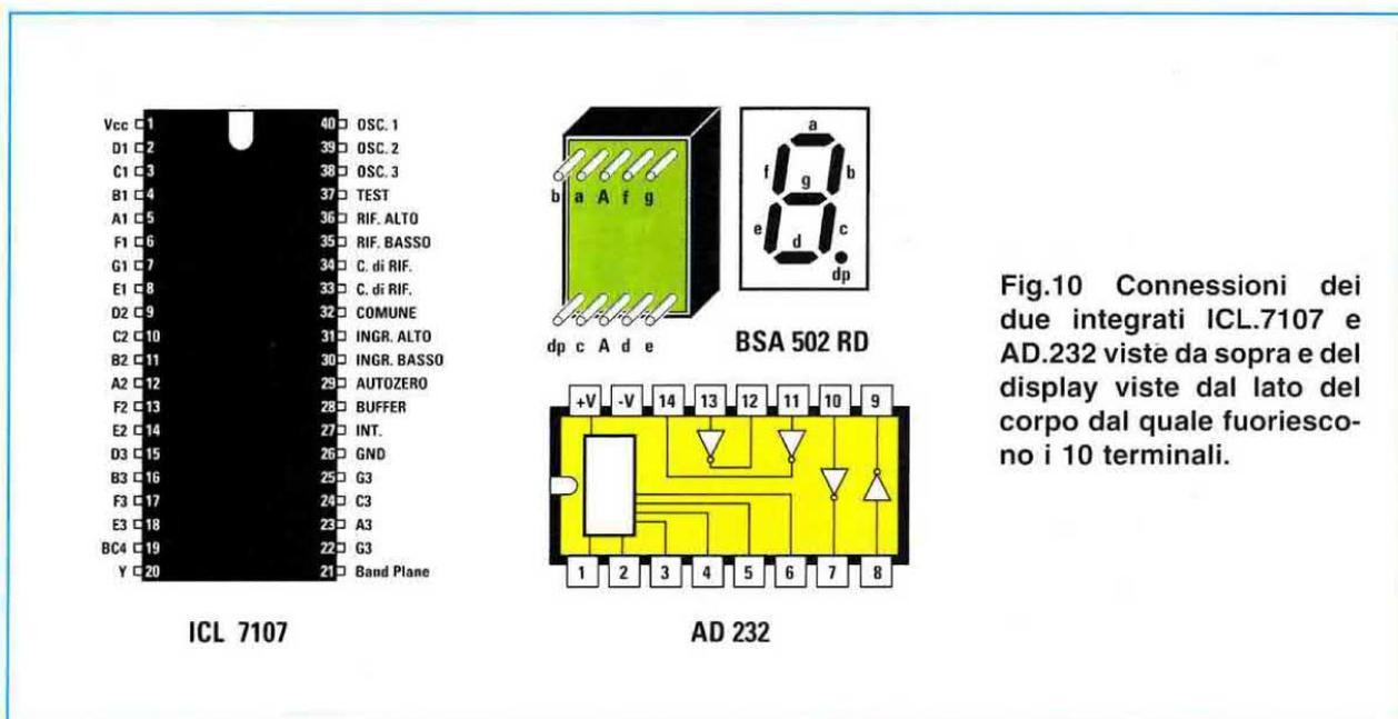
Fig.10 Connessioni dei due integrati ICL.7107 e AD.232 viste da sopra e del display viste dal lato del corpo dal quale fuoriescono i 10 terminali.
