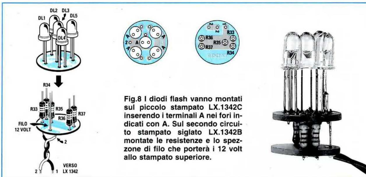
**Fig.8** I diodi flash vanno montati sul piccolo stampato LX.1342C inserendo i terminali A nei fori indicati con A. Sul secondo circuito stampato siglato LX.1342B montate le resistenze e lo spezzone di filo che porterà i 12 volt allo stampato superiore.
