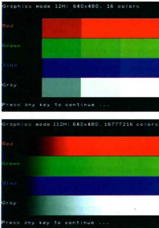
Fig.3 Pigiando un tasto qualsiasi appaiono queste finestre con sopra indicato Mode 12H o 112H ed i relativi livelli di colore.
