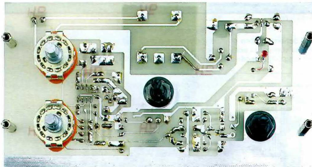
**Fig.9** Foto del circuito stampato visto dal lato opposto. Si notino ai quattro lati del circuito stampato le torrette distanziatrici in metallo, che serviranno per fissare questa ba-setta sul pannello frontale già inciso e forato, fornito assieme al mobile plastico.
