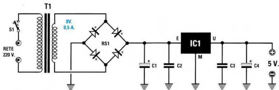
Fig.11 Poichè questo voltmetro va alimentato con una tensione stabilizzata di 5 volt, se non disponete di tale tensione vi consigliamo di usare questo semplice schema.
