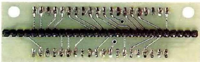
Fig.14 Sul retro della scheda display va fissato il connettore maschio da innestare nella scheda base siglata LX.1334.
