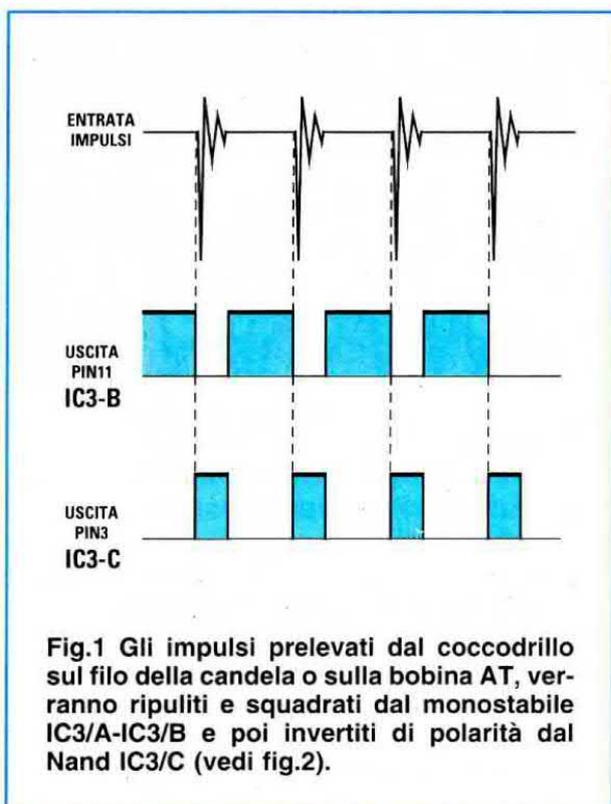
In un motore a scoppio la **scintilla** deve scoccare in **anticipo** perchè, solo in questo modo, la miscela benzina/aria ha un **tempo** sufficiente per bruciare completamente.
