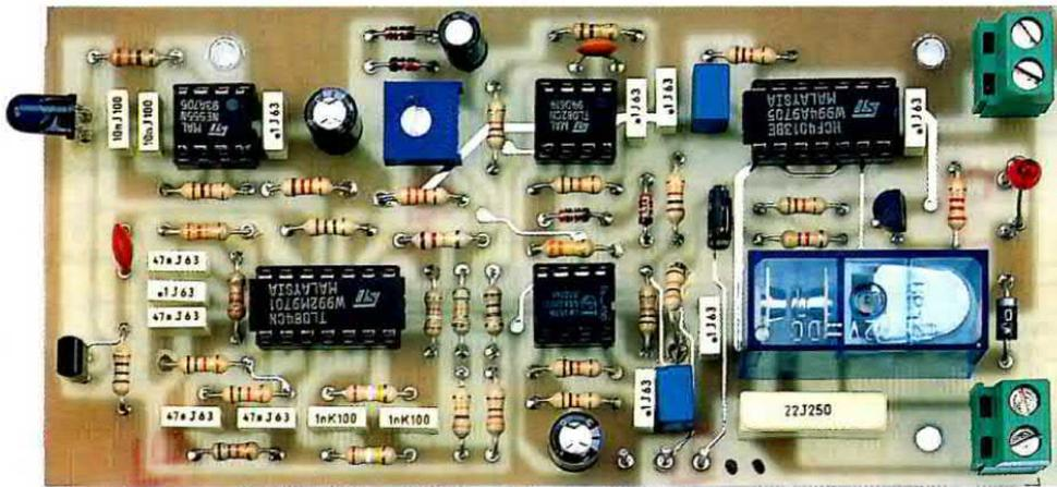
**Fig.4** Ecco come si presenta questo microswitch a montaggio ultimato. Le foto che riportiamo sono relative ai 10 primi esemplari realizzati per il collaudo, quindi sul circuito stampato non appare ancora il disegno serigrafico dei componenti e nemmeno la vernice protettiva antiossidante.
