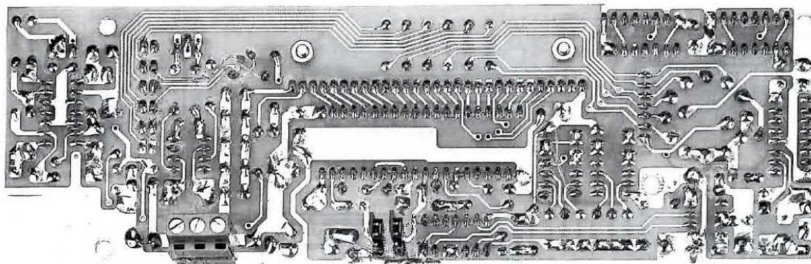
Fig.16 Foto dello stampato base LX.1340 visto dal lato delle saldature. Sulle piste in rame di questo stampato manca ancora la vernice protettiva antiossidante. Prima di inserire il commutatore rotativo S1 sul circuito stampato, accorciate il suo perno in modo da ottenere una lunghezza di circa 13 mm dalla sua estremità alla filettatura.
