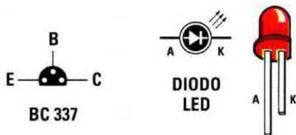
Fig.9 Di lato le connessioni del transistor BC.337 viste da sotto, cioè dal lato in cui i tre terminali fuoriescono dal corpo. Vi ricordiamo che il terminale più lungo A del diodo led DL1 è l'Anodo e il più corto è il Catodo (K).
