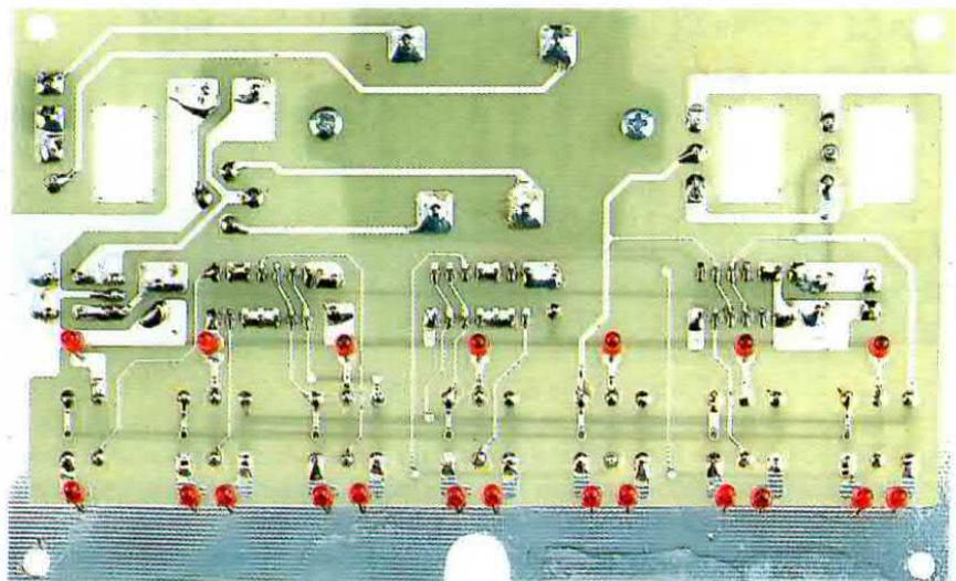
**Prima di stagnare** i loro terminali sul circuito vi consigliamo di innestare nei quattro fori dello stampato i **distanziatori metallici** inclusi nel kit, quindi inserite sul **pannello frontale** del mobile i tre deviatori **S1 - S2 - S3** e fissate il circuito stampato sul **pannello**.
