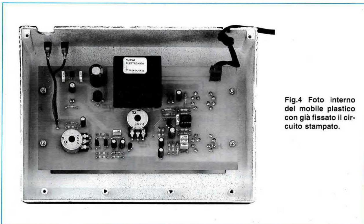
**Fig.4** Foto interno del mobile plastico con già fissato il circuito stampato.
