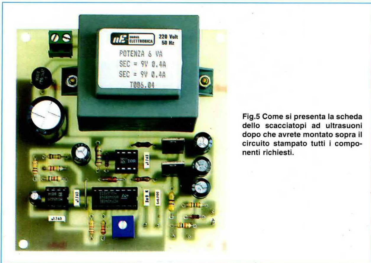
Fig.5 Come si presenta la scheda dello scacciatopi ad ultrasuoni dopo che avrete montato sopra il circuito stampato tutti i componenti richiesti.
