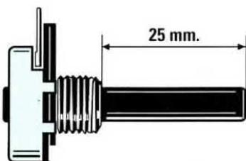
Fig.6 Con un piccolo seghetto dovete accorciare i perni dei soli potenziometri in modo che risultino della lunghezza di 25 mm circa come visibile nel disegno.
