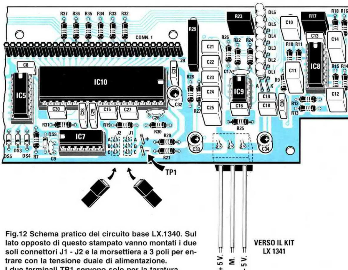
Fig.12 Schema pratico del circuito base LX.1340. Sul lato opposto di questo stampato vanno montati i due soli connettori J1 - J2 e la morsettiere a 3 poli per entrare con la tensione duale di alimentazione. I due terminali TP1 servono solo per la taratura.
