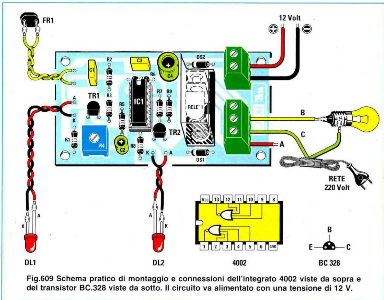
Fig.609 Schema pratico di montaggio e connessioni dell'integrato 4002 viste da sopra e del transistor BC.328 viste da sotto. Il circuito va alimentato con una tensione di 12 V.
