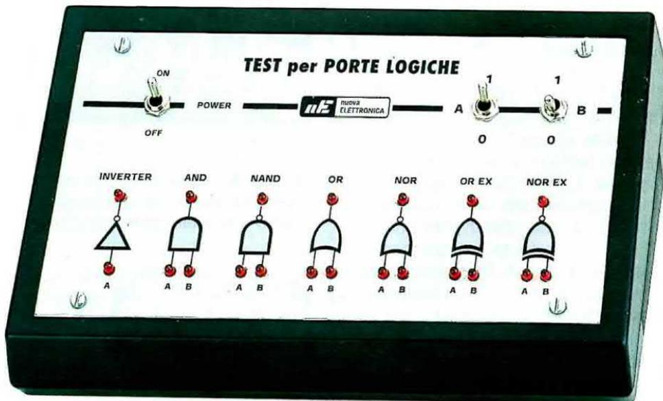
**Fig.602** Una volta completato il montaggio vi accorgete quanto risulti utile questo semplice progetto, perché vi permetterà di sapere istantaneamente quale Livello logico appare sull'uscita di una Porta modificando i Livelli logici sugli ingressi.
