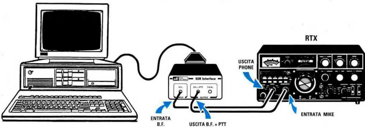
Fig.10 Chi dispone di un Ricetrasmittente, quindi oltre a ricevere vorrà anche trasmettere segnali SSTV e RTTY, dovrà utilizzare anche le due uscite BF-PTT presenti in questa interfaccia inserendole nell'ingresso Mike in sostituzione del microfono.
