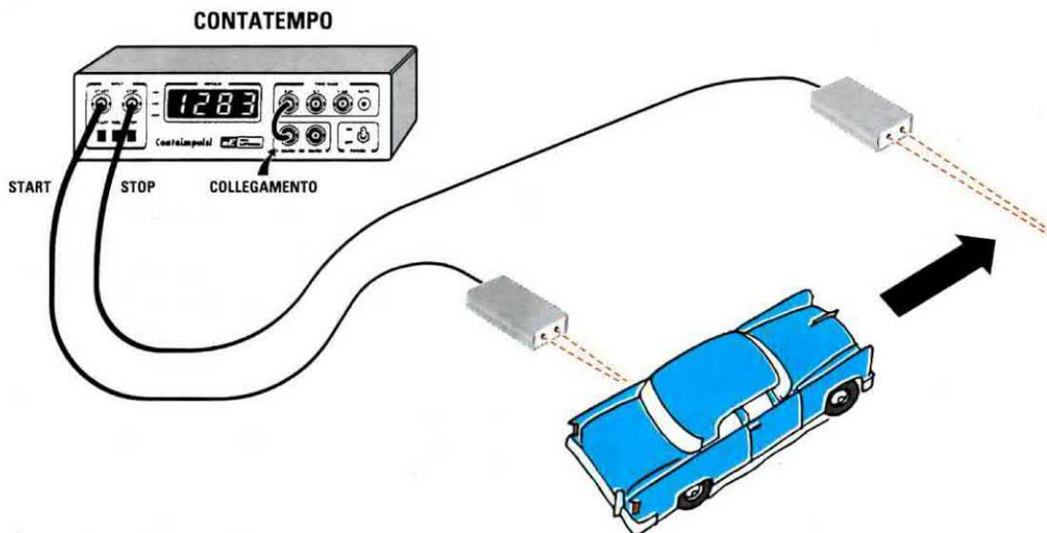
Fig.8 Applicando due microswitches ai bordi di un'autopista, potrete misurare il tempo, in centesimi e millesimi di secondo, trascorso per percorrere mezzo giro o un giro completo. Le uscite M-B di un sensore vanno collegate all'ingresso Start del contatempo LX.1188 e le uscite M-B del secondo sensore all'ingresso Stop dell'LX.1188. Per usare il kit LX.1188 come contatempo, è necessario che al suo interno sia presente una Base tempi quarzata (LX.1189) come spiegato nella rivista N.175/176.
