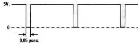
Fig.2 Le diverse frequenze che preleviamo sui diodi da DS1 a DS8 prima di essere applicate sul piedino 2 del C/Mos 7555 siglato IC1, vengono convertite in impulsi negativi della durata di **0,05 μS** dagli inverter siglati IC7/C - IC7/B - IC7/A.
