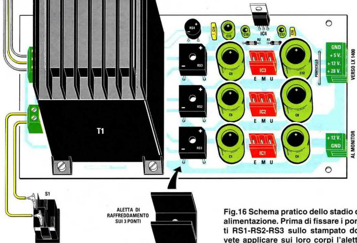
Fig.16 Schema pratico dello stadio di alimentazione. Prima di fissare i ponti RS1-RS2-RS3 sullo stampato dovette applicare sui loro corpi l'aletta ad U di raffreddamento.
