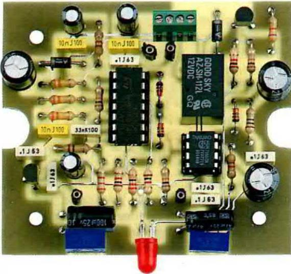
Fig.6 Come si presenta la basetta del circuito stampato LX.1396 dell'antifurto dopo che avrete montato tutti i componenti visibili nello schema pratico di fig.7
