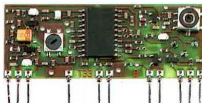
**Fig.2** Caratteristiche e foto a grandezza naturale del modulo ricevente KM01.40.
