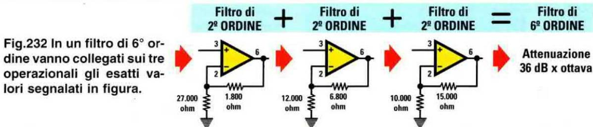
Fig.232 In un filtro di 6° ordine vanno collegati sui tre operazionali gli esatti valori segnalati in figura.
