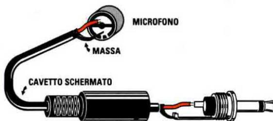
Fig.7 Per inviare il segnale microfonico sull'ingresso del trasmettente dovete utilizzare uno spinotto jack maschio.
