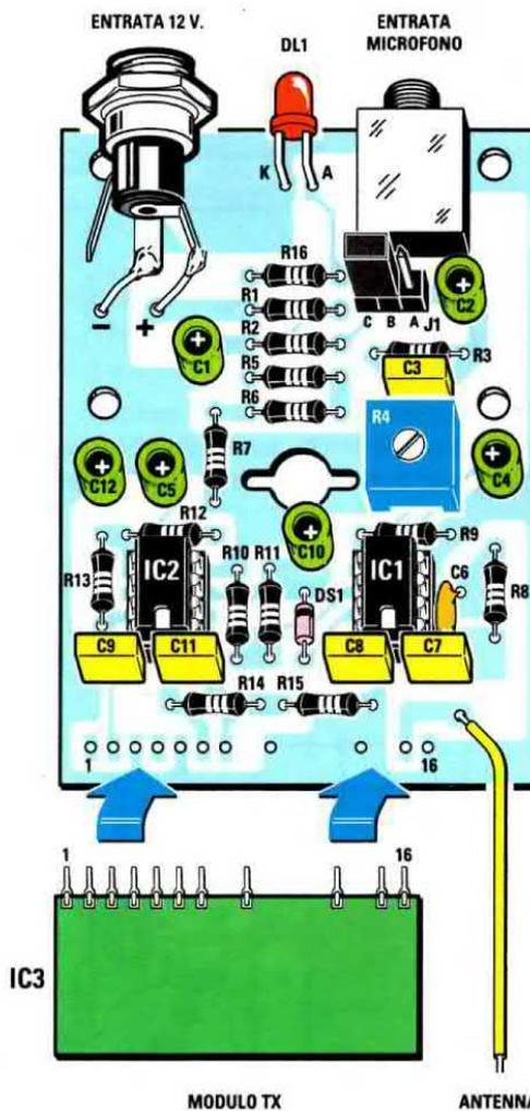
Fig.6 Schema pratico di montaggio dello stadio trasmettente. I terminali del modulo **KM01.41** vanno inseriti e saldati nei fori presenti in basso nello stampato.
