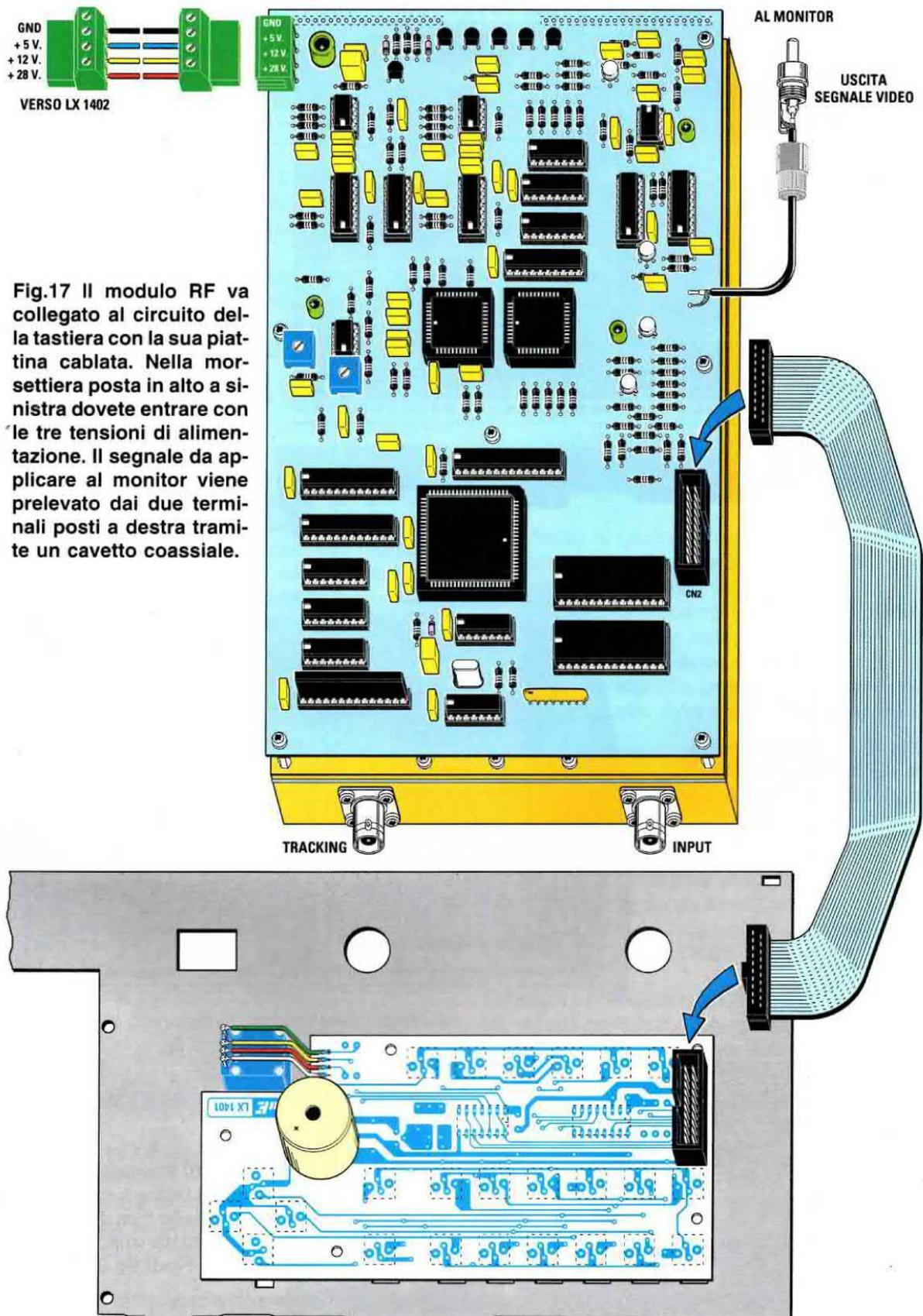
**Fig.17** Il modulo RF va collegato al circuito della tastiera con la sua piastrina cablata. Nella morsettiera posta in alto a sinistra dovete entrare con le tre tensioni di alimentazione. Il segnale da applicare al monitor viene prelevato dai due terminali posti a destra tramite un cavetto coassiale.
