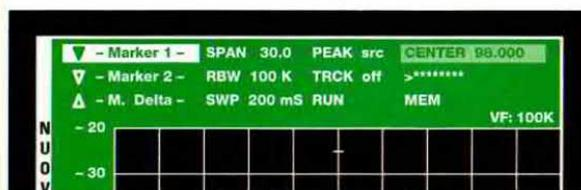
Fig.47 Per usare il Marker 1 portate il cursore su questa scritta pigiando il tasto funzione F2 e il tasto numerico 0.
