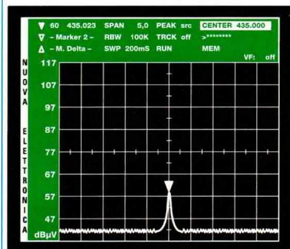
Fig.61 Nella riga **Center** digitate la frequenza della **2<sup>a</sup>** armonica e pigiate **Enter**.
