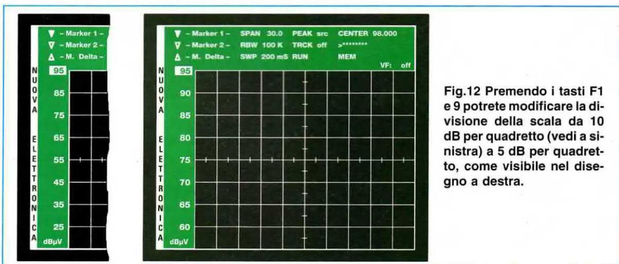
Fig.12 Premendo i tasti F1 e 9 potrete modificare la divisione della scala da 10 dB per quadretto (vedi a sinistra) a 5 dB per quadretto, come visibile nel disegno a destra.
