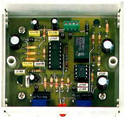
**Fig.8** All'interno del suo piccolo mobiletto plastico fissate con tre viti autofilettanti il circuito stampato. Sul pannello frontale dovete fare tre fori, uno per far uscire la testa del diodo led e due per poter ruotare con un cacciavite i cursori dei trimmer.
