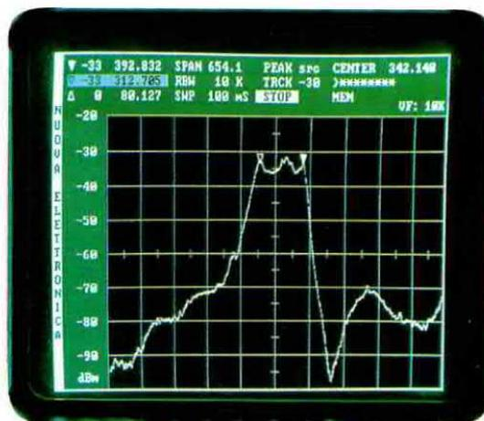
Usando la funzione Tracking potrete controllare qualsiasi filtro Passa/Banda e stabilire la sua larghezza di banda ponendo i cursori dei Marker sugli estremi della curva.
