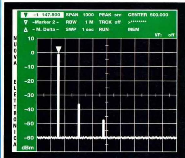
**Fig.51** Riducendo la sensibilità noterete che la traccia della frequenza fondamentale rientrerà nel quadro. Per conoscere il valore della sua ampiezza dovrete pigiare i tasti F2, 0 ed Enter per rendere attivo il Marker 1, dopodiché dovrete ruotare la manopola dell'Encoder in modo da portare la V in corrispondenza della sommità della traccia. Nel rettangolo del Marker 1 appariranno la frequenza e l'ampiezza del segnale.
