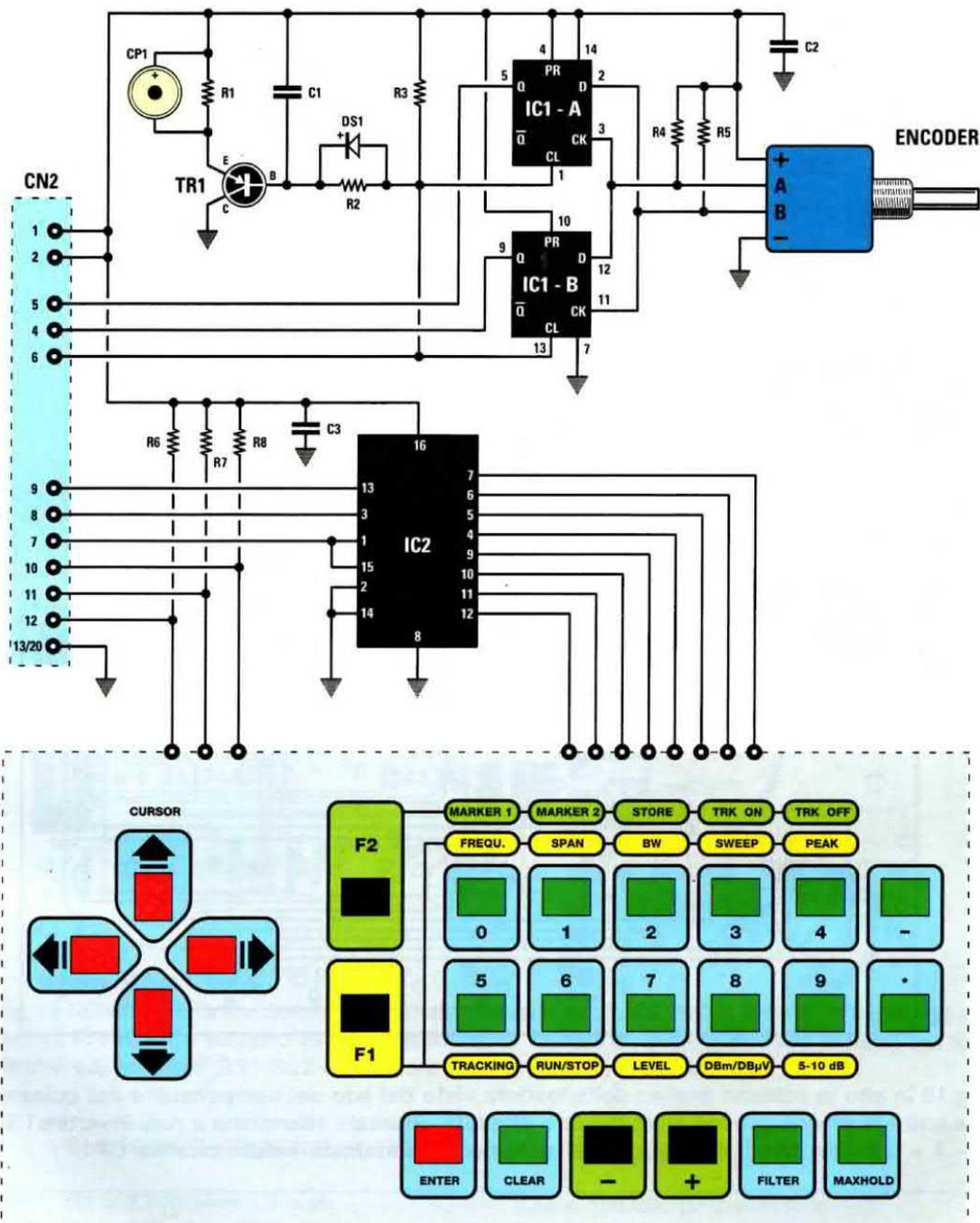
Fig.12 Schema elettrico dello stadio tastiera LX.1401. Lo schema pratico è in fig.13.
