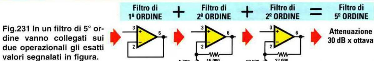
Fig.231 In un filtro di 5° ordine vanno collegati sui due operazionali gli esatti valori segnalati in figura.
