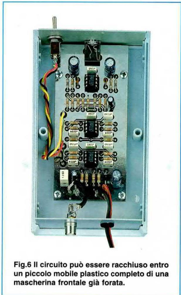
Fig.6 Il circuito può essere racchiuso entro un piccolo mobile plastico completo di una mascherina frontale già forata.
