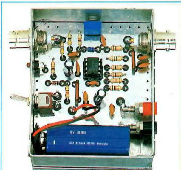
Fig.1 Il Ponte visto dal lato dei componenti. La pila va inserita nel vano in basso.
