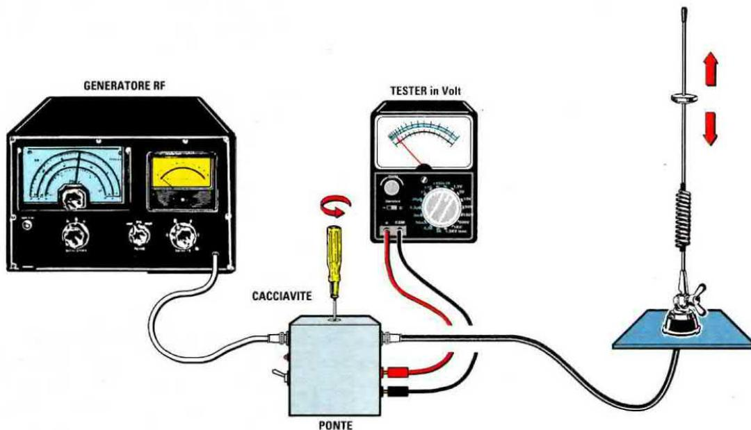
**Fig.14** Per controllare su quale frequenza si accorda un'antenna a stilo ricetrasmittente, dovete prima fissarla sulla carrozzeria di un'auto, collegando poi all'ingresso del ponte il Generatore RF e, alla sua uscita, il cavo coassiale dello stilo. Dopo aver ruotato il trimmer R3 sul valore ohmico di 52 ohm, dovete ruotare la sintonia del Generatore fino a trovare il valore di frequenza che farà deviare la lancetta del tester sugli 0 volt.
