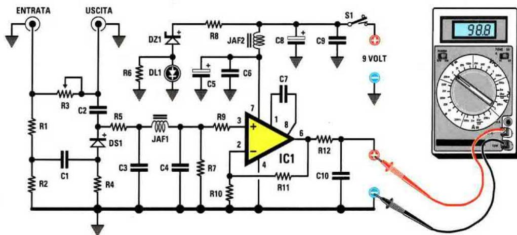
Fig.4 Un valido Ponte per misurare il valore d'impedenza di un'antenna è invece un po' più complesso perchè, come evidenziato in questo schema elettrico, il segnale RF rad-dizzato dal diodo DS1 deve essere amplificato con l'integrato IC1. Sull'ingresso di questo Ponte NON dovete mai applicare il segnale RF prelevato dall'uscita di un trasmettitore, ma solo dei segnali prelevati dall'uscita di un qualsiasi Generatore RF.
