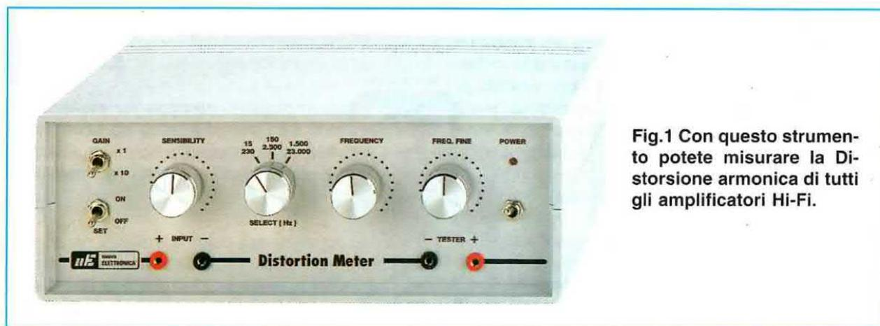
Fig.1 Con questo strumento potete misurare la Distorsione armonica di tutti gli amplificatori Hi-Fi.
