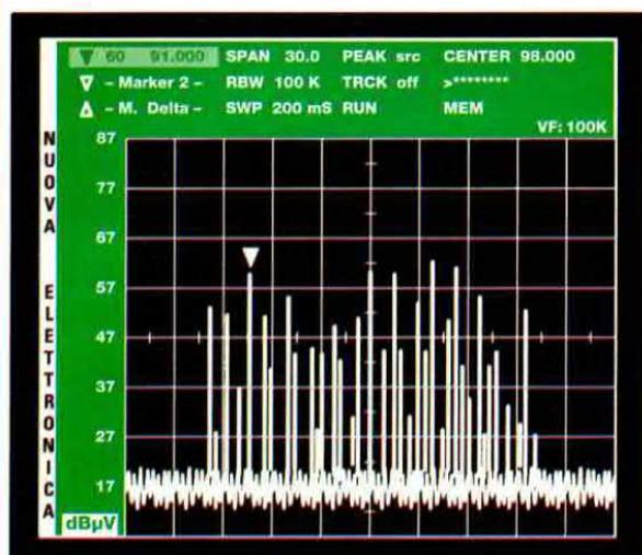
Fig.49 Se volete conoscere l'ampiezza in dBμV anziché in dBm, dovrete premere il tasto funzione F1 poi il tasto numerico 8.
