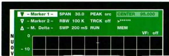
Fig.17 Se premete i tasti F2 e 0, il cursore si porterà sulla scritta Marker 1. Premendo il tasto Enter apparirà un cursore a V che potrete posizionare su ogni portante tramite l'Encoder. Nella riga del Marker apparirà la frequenza e l'ampiezza del segnale sul quale avrete posto la V.
