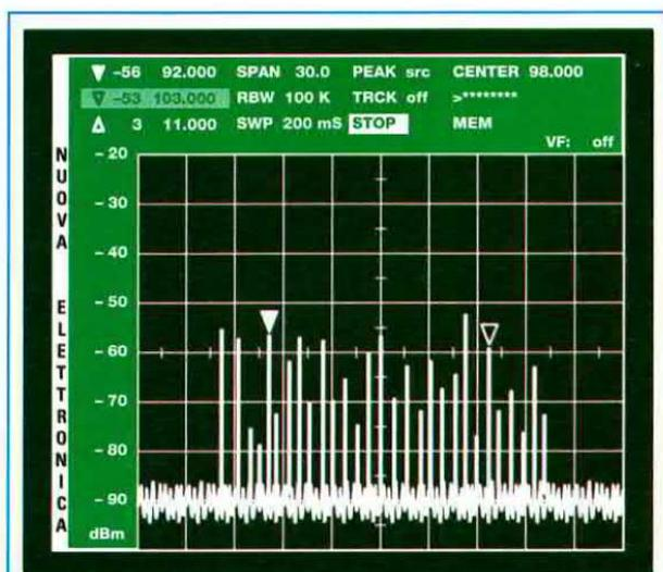
**Fig.19** Se premete i tasti **F1** e **6**, il cursore si posizionerà sulla scritta **Run**. Premendo il tasto **Enter** questa scritta cambierà in **Stop** ed in questo modo l'immagine si bloccherà. Per sbloccarla ripiagate **Enter**.
