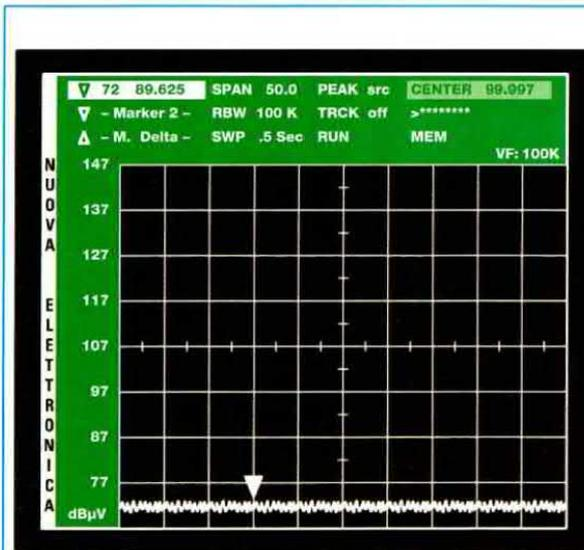
Fig.28 Per memorizzare un secondo e differente setup di parametri, portate il cursore su Mem poi pigiate Enter.
