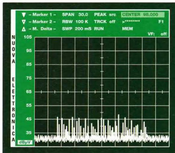
**Fig.10** Se volete passare dai dBm ai dB $\mu$ V pigiate i tasti **F1**, **8** e poi **Enter**. Quando pigiate **F1**, controllate sempre che questa scritta appaia a destra degli asterischi. Se pigiate troppo velocemente, la scritta **F1** non apparirà.
