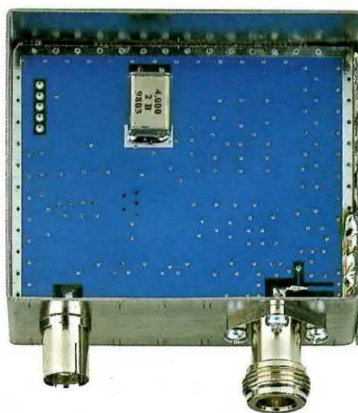
**Fig.3** Estraindo il coperchio inferiore del contenitore, vedrete saldato sul circuito stampato il solo quarzo da 4 MHz utilizzato dall'integrato PLL (vedi IC4 in fig.5) per ottenere la frequenza di riferimento.
