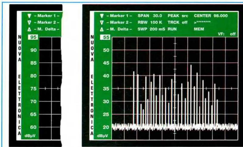
Fig.13 Se dopo essere passati sulla divisione 5 dB per quadretto premete F1 e 9, la scala visualizzata andrà da 55 a 20 dB $\mu$ V. Nella figura precedente (vedi a sinistra) la scala andava da 95 a 60 dB $\mu$ V.
