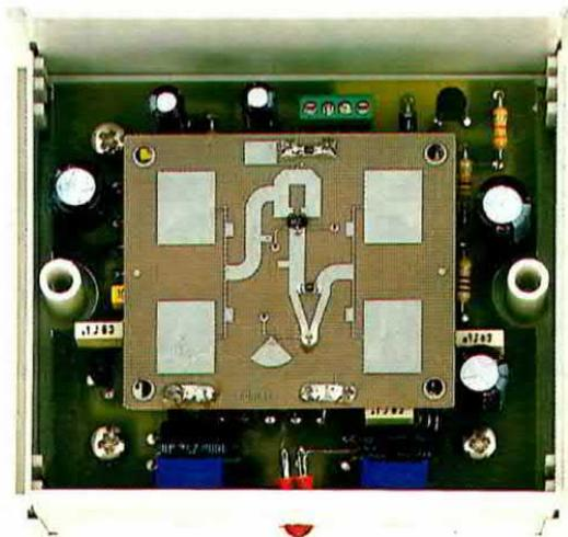
**Fig.9** Sopra il circuito stampato LX.1396 va innestato il modulo DRO, poi la scatola viene chiusa con il suo coperchio. Non è necessario fare una finestra sul coperchio perché il fascio delle onde a 10 GHz lo attraverserà senza nessuna attenuazione.
