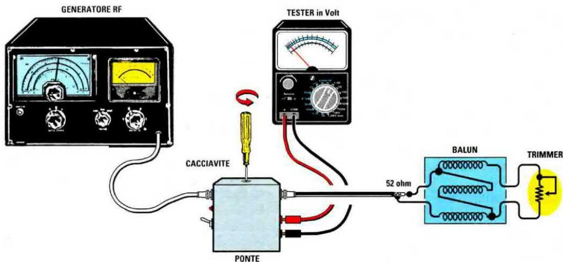
**Fig.15** Per controllare il rapporto di trasformazione del Balun dovete ruotare il cursore del trimmer R3 fino a leggere 52 ohm, dopodichè collegare all'uscita del Ponte l'avvolgimento primario del Balun. Dopo aver sintonizzato il Generatore sulla frequenza di lavoro, ruotate il cursore del trimmer da 500 ohm posto sul secondario del Balun fino a far deviare la lancetta del tester su 0 volt. Per conoscere il rapporto di trasformazione basta leggere il valore ohmico del trimmer da 500 ohm.
