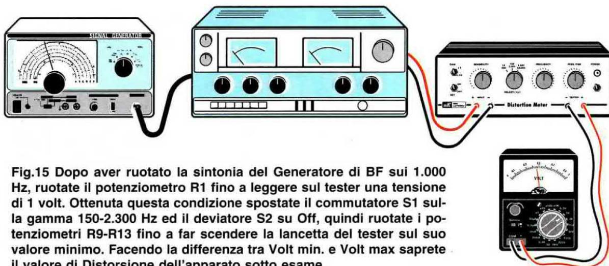
Fig.15 Dopo aver ruotato la sintonia del Generatore di BF sui 1.000 Hz, ruotate il potenziometro R1 fino a leggere sul tester una tensione di 1 volt. Ottenuta questa condizione spostate il commutatore S1 sulla gamma 150-2.300 Hz ed il deviatore S2 su Off, quindi ruotate i potenziometri R9-R13 fino a far scendere la lancetta del tester sul suo valore minimo. Facendo la differenza tra Volt min. e Volt max saprete il valore di Distorsione dell'apparato sotto esame.
