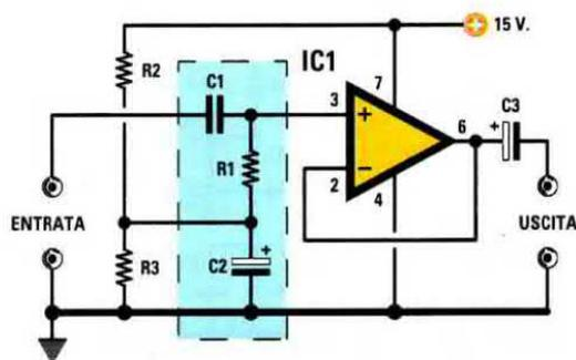
Fig.212 Se volessimo alimentare il filtro passa-alto di fig.211 con una tensione Singola, dovremmo aggiungere due resistenze da 10.000 ohm (vedi R2-R3) ed applicare un condensatore elettrolitico da 10 microfarad sull'uscita (vedi C3).
