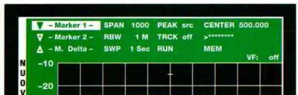
**Fig.54** Per attivare e disattivare i **Marker** dovete portare il cursore su queste scritte e premere il tasto **Enter**.
