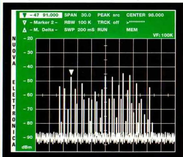
Fig.48 Portate la V sulla sommità di un segnale ruotando la manopola dell'Encoder, conoscerete così frequenza ed ampiezza.
