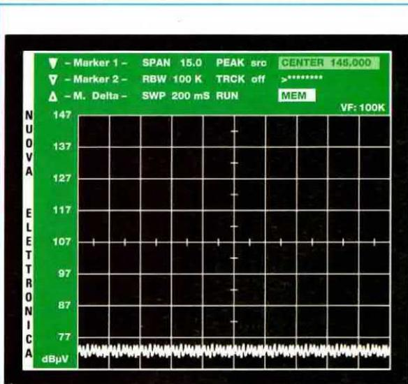
Fig.25 Per memorizzare i parametri del primo menu, portate il cursore su Mem e pigiate Enter: apparirà il menu di fig.26.
