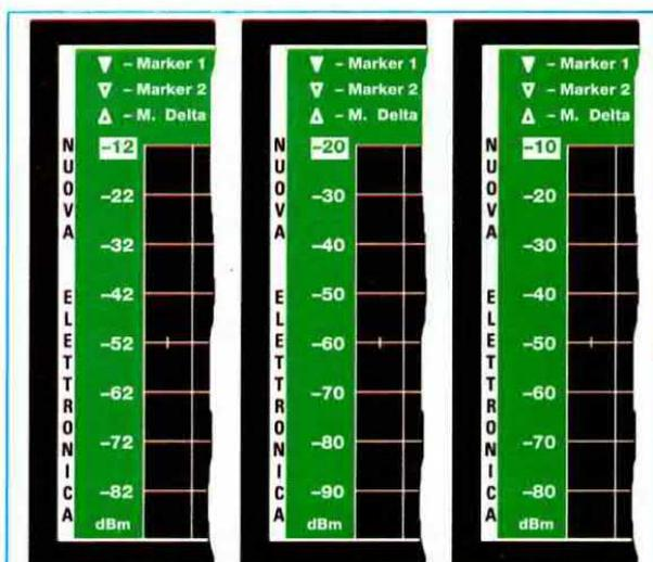
**Fig.7** Dopo aver premuto **F1** e **7**, il cursore si porta sul numero in alto della scala. Premendo i tasti **-/+** della tastiera potrete modificare la sensibilità. Ruotando la manopola dell'Encoder potrete variare i valori con passi di **2 dB** in meno o in più.
