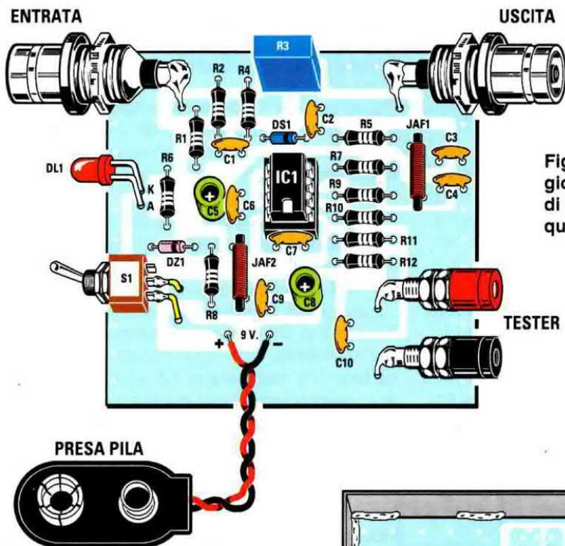
Fig.5 Schema pratico di montaggio del Ponte, che vi permetterà di misurare l'impedenza di una qualsiasi antenna.
