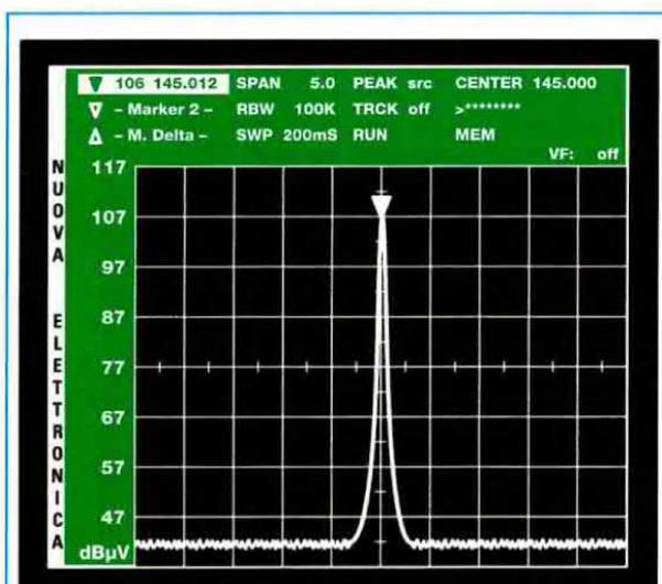
Fig.59 Se volete la misura in **dB $\mu$ V** pigiate il tasto **F1**, il tasto **8**, poi il tasto **Enter**.
