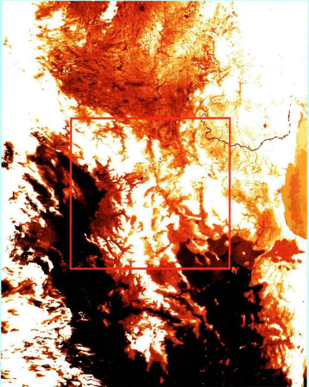
**Fig.12** Approfittando dell'orbita di un satellite polare HRPT che passava sopra ai Balcani, abbiamo memorizzato la sola immagine all'infrarosso per vedere se fossero visibili gli incendi delle città del Kosovo colpite dai missili. In questa foto si vedono al centro dei piccoli puntini che risultano molto più scuri delle città perchè gli incendi, provocando un aumento della temperatura, vengono messi maggiormente in risalto (fig.13).
