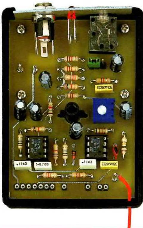
Fig.13 (Foto a sinistra) Dopo aver saldato i terminali del modulo trasmettente KM01.41 sul circuito stampato, lo dovete ripiegare a L in modo da poter chiudere il coperchio del mobile. Il filo dell'antenna va saldato sul terminale a spillo posto vicino al condensatore C7 (vedi fig. 6).
