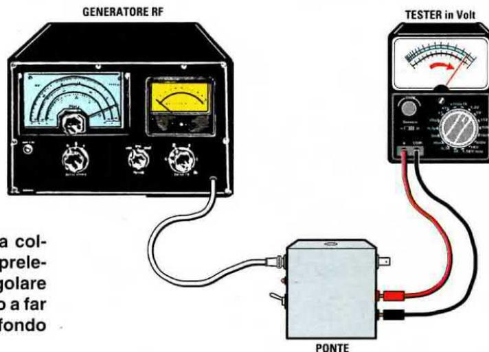
Fig.9 Per collaudare il Ponte basta collegare al suo ingresso il segnale prelevato da un Generatore RF, poi regolare l'ampiezza del segnale d'uscita fino a far deviare la lancetta del tester sul fondo scala di 1 oppure 1,5 volt.
