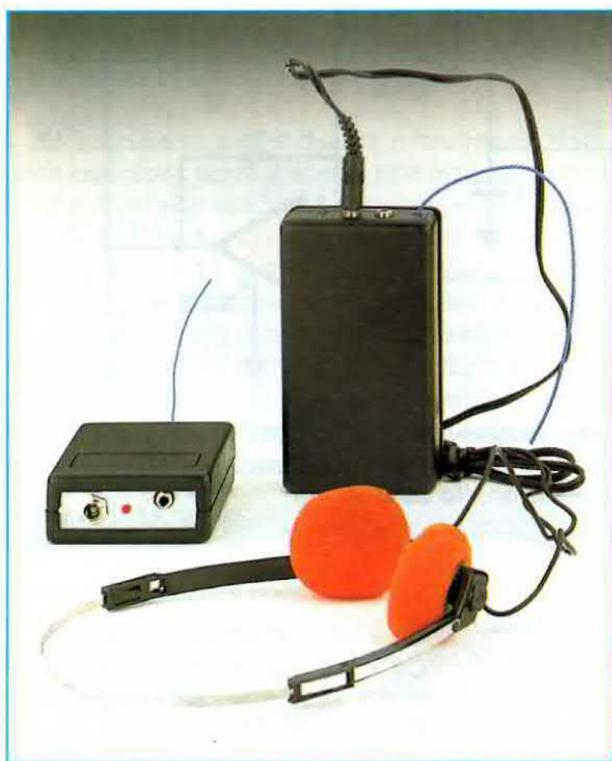
**Fig.3** Il piccolo trasmettitore deve essere alimentato esternamente con una tensione di 12 volt, mentre il ricevitore dispone di un apposito vano per una pila da 9 volt.
