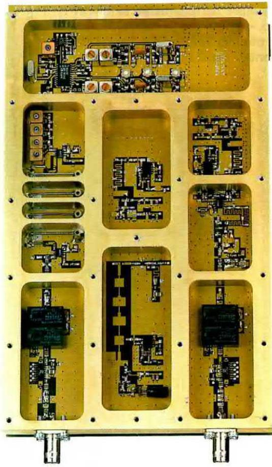
Fig.8 All'interno del blocco fresato sono racchiusi tutti gli stadi RF più il generatore di Tracking. NON aprite questo blocco perché ciò che contiene si vede nella foto.
