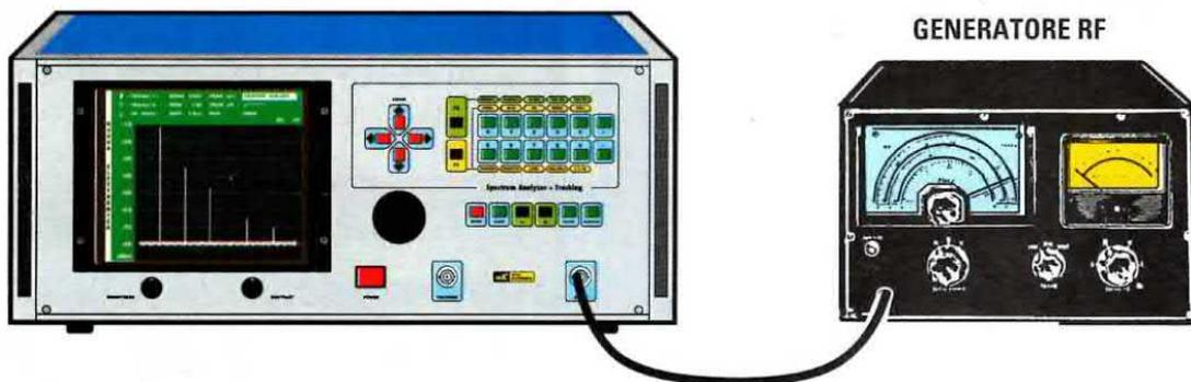
Fig.36 Il segnale che preleverete sull'uscita di un Generatore RF può essere direttamente collegato sull'ingresso dell'Analizzatore. Potrete effettuare le misure d'ampiezza sia in dBm sia in dB $\mu$ V utilizzando i pulsanti F1 ed F2 come spiegato nel testo.
