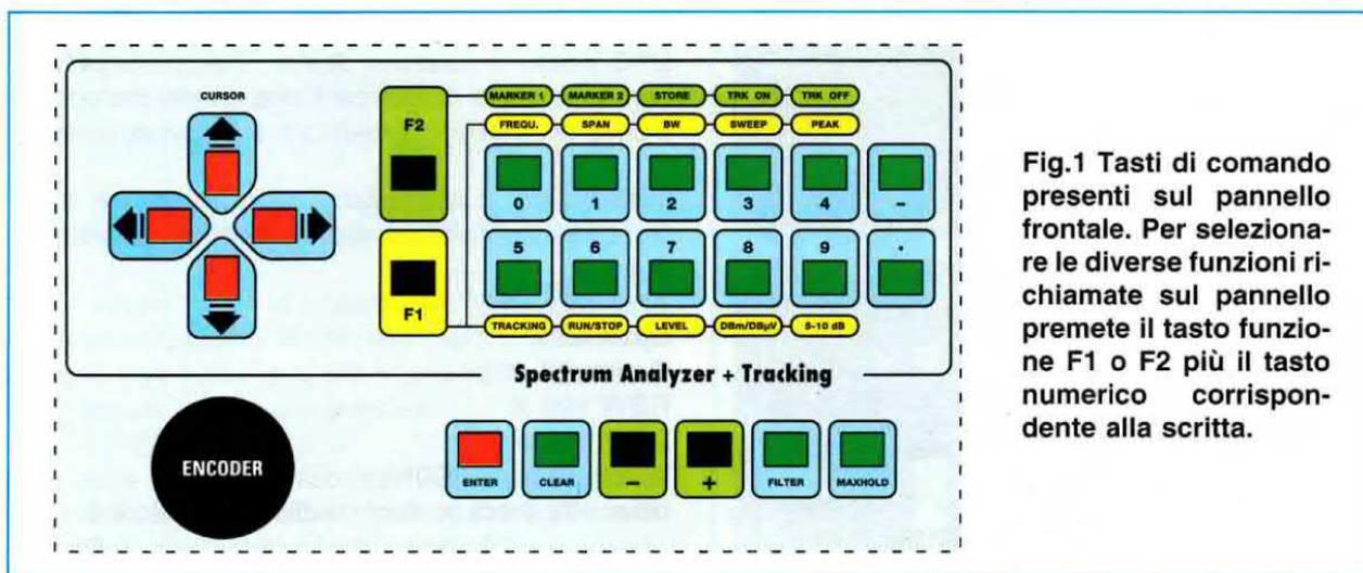
Fig.1 Tasti di comando presenti sul pannello frontale. Per selezionare le diverse funzioni richiamate sul pannello premete il tasto funzione F1 o F2 più il tasto numerico corrispondente alla scritta.
