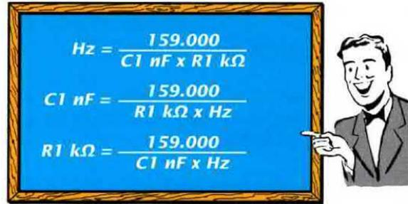
**Fig.209** Filtro passa-basso di 1° ordine alimentato con una tensione Duale. Questo filtro attenuerà di 3 dB la frequenza di taglio e di 6 dB tutte le ottave superiori. Nel testo abbiamo riportato un esempio di come calcolare l'attenuazione per ogni ottava.
