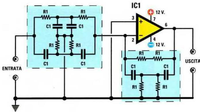
Fig.226 Per realizzare un filtro notch di 2° ordine alimentato con una tensione Duale vi consigliamo di utilizzare questo schema.
