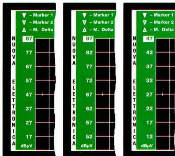
Fig.21 La massima sensibilità in dB $\mu$ V, con una divisione di 10 dB per quadretto, si ha quando in alto sulla scala appare il numero 87. Pigiando F1 e 9 la scala passerà sulla divisione di 5 dB per quadretto (vedi figura centrale). Se ripigerete F1 e 9 aumenterete ulteriormente la sensibilità, perché la scala passerà sui 47 dB $\mu$ V.
