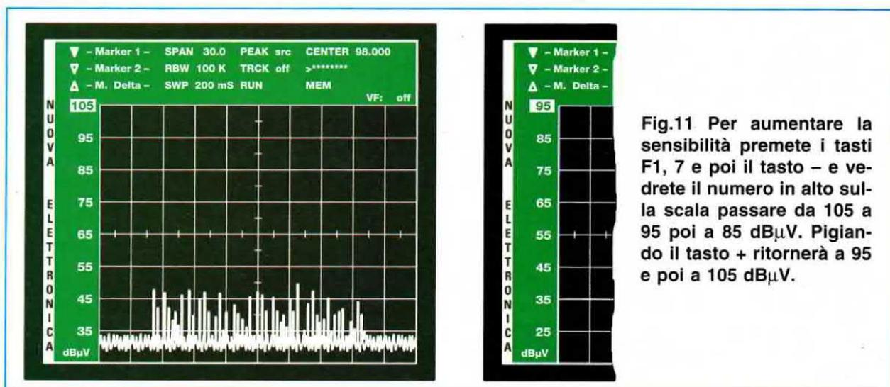
Fig.11 Per aumentare la sensibilità premete i tasti F1, 7 e poi il tasto - e vedrete il numero in alto sulla scala passare da 105 a 95 poi a 85 dBµV. Pigiando il tasto + ritornerà a 95 e poi a 105 dBµV.
