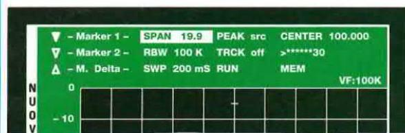
Fig.3 Premendo i tasti F1 e 1 potrete cambiare il valore nella riga Span.
