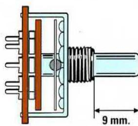
Fig.6 La lunghezza dei perni dei tre potenziometri deve essere di circa 24 mm, mentre quella del commutatore S1 di circa 9 mm.
