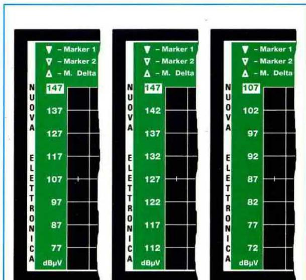
Fig.23 La minore sensibilità in dBµV, con una divisione di 10 dB per quadretto, si ha quando in alto sulla scala appare il numero 147. Pigiando F1 e 9 la scala passerà sulla divisione di 5 dB per quadretto (vedi figura centrale). Se ripigerete F1 e 9 ridurrete ulteriormente la sensibilità, perché la scala passerà sui 107 dBµV.
