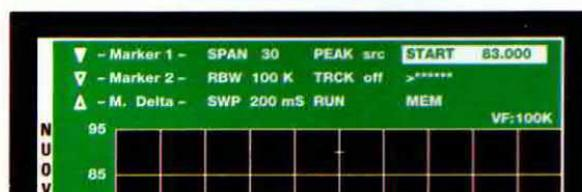
Fig.16 Se portate il cursore sulla riga Center poi pigiate Enter, questa scritta cambierà in Start. Se premete F1 e 4 in modo da portarvi sulla riga Peak e poi pigiate Enter, la portante d'ampiezza maggiore si posizionerà all'estrema sinistra.
