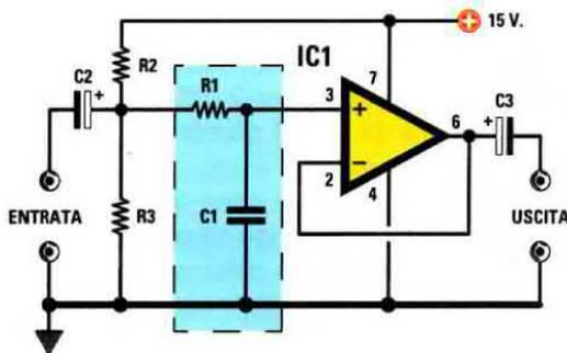
**Fig.210** Se volessimo alimentare il filtro passa-basso di fig.209 con una tensione Singola, dovremmo aggiungere due resistenze da **10.000 ohm** (vedi R2-R3) ed applicare un condensatore elettrolitico da **47 microfarad** sull'ingresso e sull'uscita.
