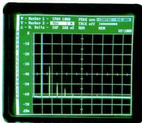
Fig.2 Applicando sull'ingresso di un Analizzatore di Spettro un segnale RF, sullo schermo vedremo apparire il valore della sua ampiezza espresso in dBm o dBμV, la sua frequenza espressa in MHz e tutte le armoniche generate dal segnale.
