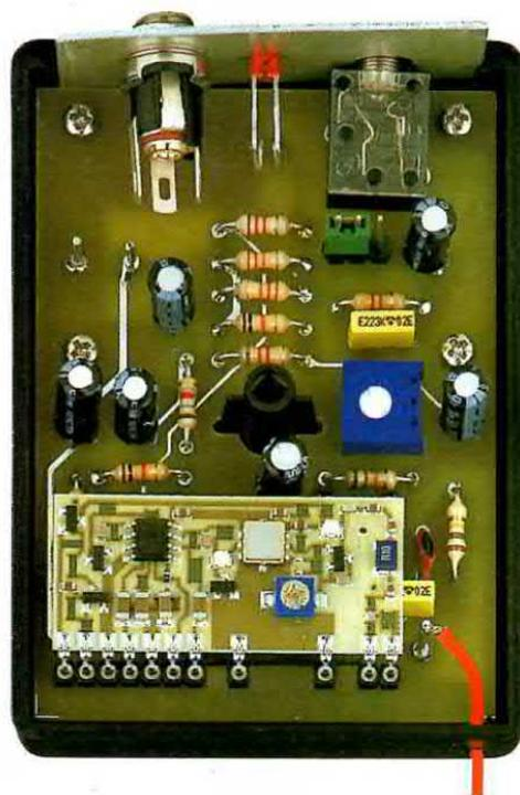
Fig.12 (Foto in alto) Prima di inserire il circuito stampato all'interno del mobile dovette forare il pannellino frontale per inserire la presa di alimentazione, far fuoriuscire la testa del diodo led e la presa femmina jack per il microfono.
