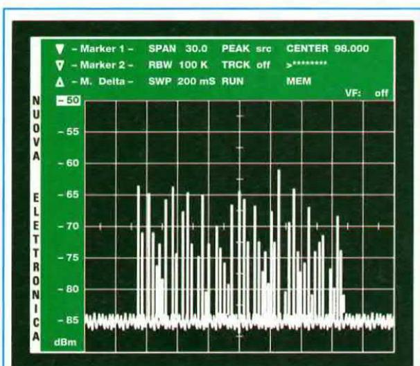
**Fig.9** Se dopo essere passati sulla divisione 5 dB per quadretto premete nuovamente F1 e 9, la scala visualizzata andrà da -50 a -85 dBm. Nella scala riportata in fig.8 la scala andava da -10 a -45 dBm.
