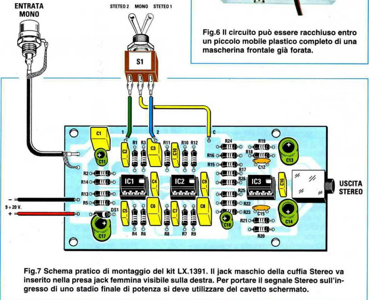
Fig.7 Schema pratico di montaggio del kit LX.1391. Il jack maschio della cuffia Stereo va inserito nella presa jack femmina visibile sulla destra. Per portare il segnale Stereo sull'ingresso di uno stadio finale di potenza si deve utilizzare del cavetto schermato.
