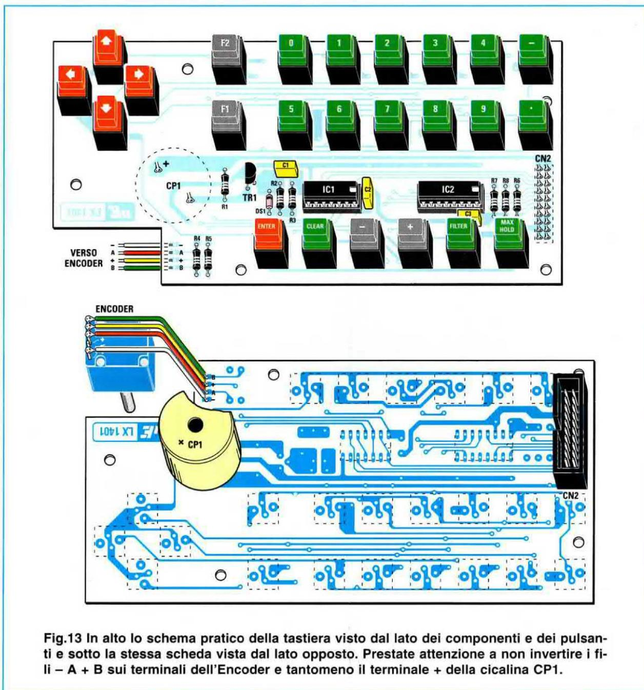
**Fig.13** In alto lo schema pratico della tastiera visto dal lato dei componenti e dei pulsanti e sotto la stessa scheda vista dal lato opposto. Prestate attenzione a non invertire i fili - A + B sui terminali dell'Encoder e tantomeno il terminale + della cicalina CP1.
