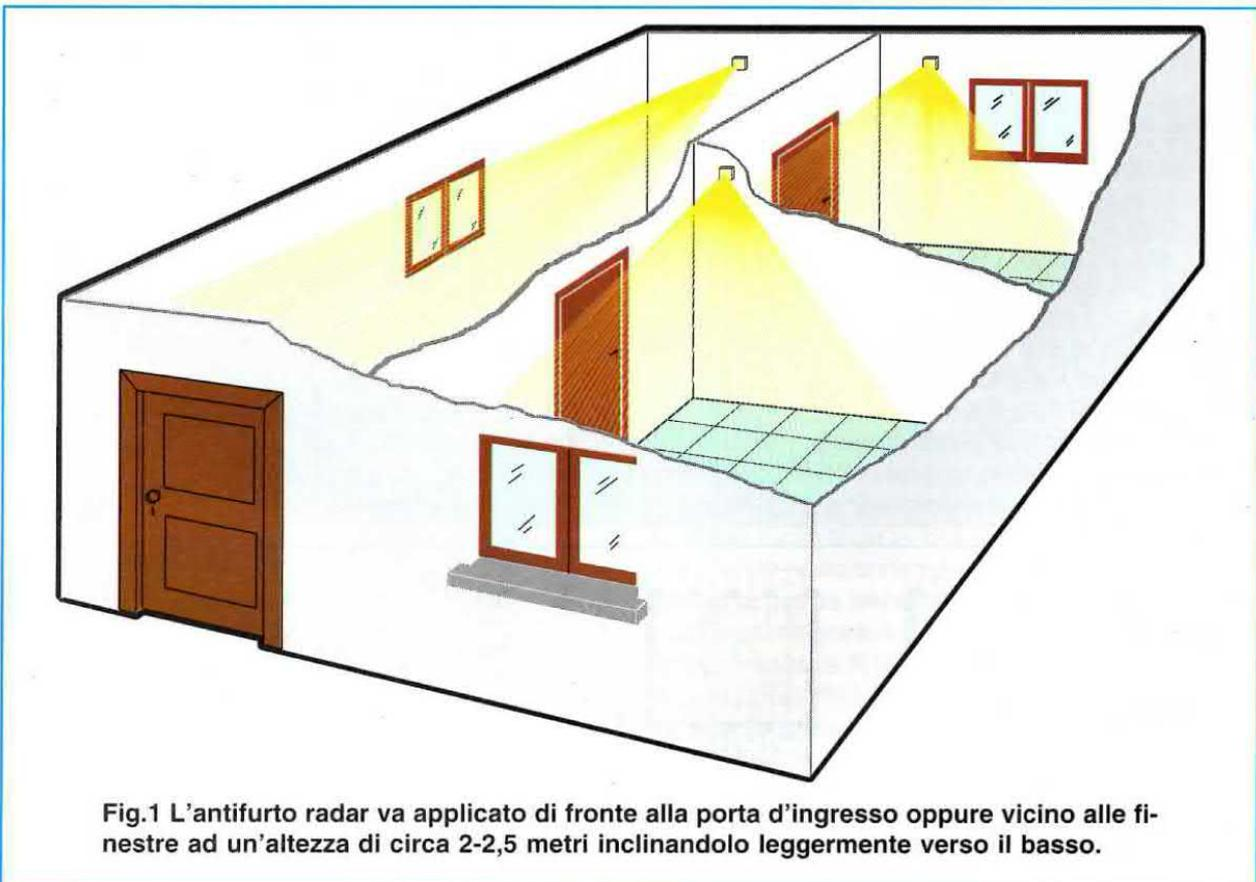
Fig.1 L'antifurto radar va applicato di fronte alla porta d'ingresso oppure vicino alle finestre ad un'altezza di circa 2-2,5 metri inclinandolo leggermente verso il basso.
