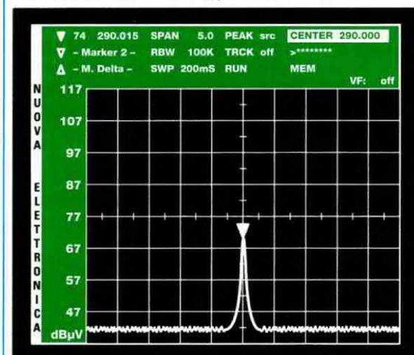
Fig.60 Nella riga **Center** digitate la frequenza della **1<sup>a</sup>** armonica e pigiate **Enter**.
