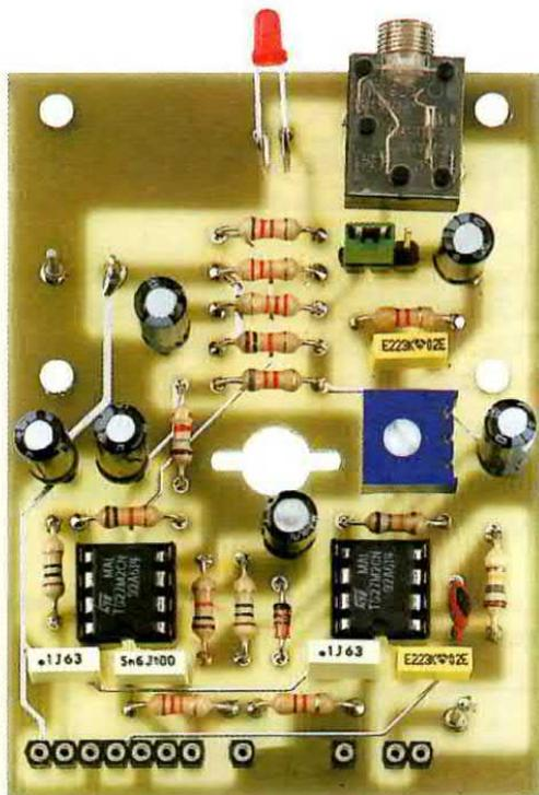
Fig.11 Ecco come si presenta a montaggio ultimato lo stadio trasmettente LX.1388. Il trimmer posto sulla destra del circuito stampato serve per modificare la sensibilità del microfono. Il diodo led DL1, può anche venire escluso dal circuito.
