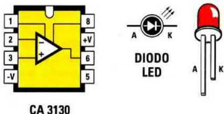
Fig.8 Connessioni dell'operazionale IC1 siglato CA.3130 viste da sopra e quelle del diodo led. Come potete vedere in fig.5, il terminale più lungo del diodo indicato A deve essere rivolto verso l'interruttore S1.
