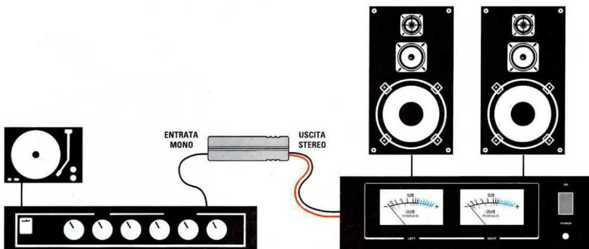
**Fig.8** Per entrare nell'ingresso di uno stadio finale di potenza bisogna prelevare il segnale dall'uscita Mono di un qualsiasi preamplificatore provvisto di controllo di Tono e Volume, poi il segnale Stereo prelevato dall'uscita del convertitore Mono-Stereo va inserito, per mezzo di due cavetti schermati, nei due ingressi Destro-Sinistro dello stadio finale.
