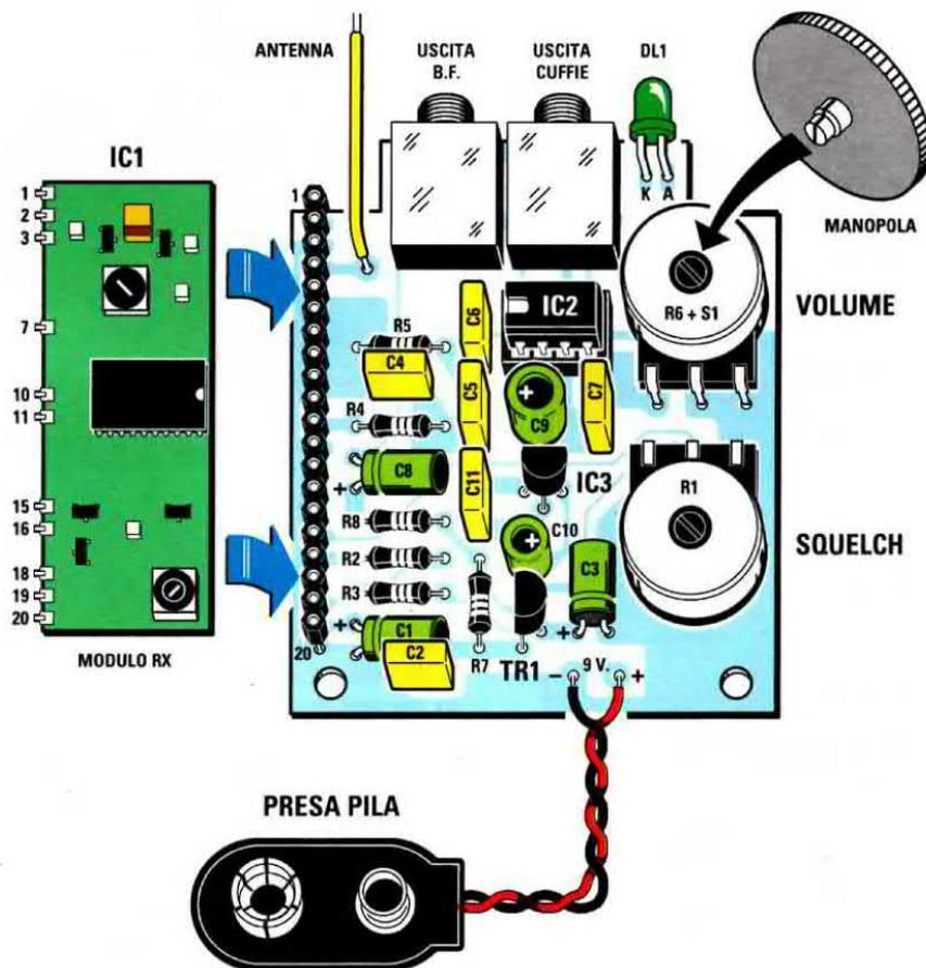
**Fig.10** Schema pratico di montaggio dello stadio ricevente. Il modulo **KM01.40** va innestato nel connettore femmina preventivamente saldato sul lato sinistro (vedi fig.14).
