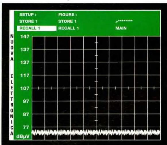
Fig.32 Portate il cursore su Recall 1 poi pigiate Enter e i dati memorizzati in Store 1 riappariranno sul monitor nel 1° menu.
