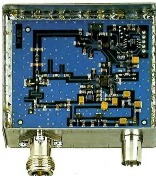
**Fig.2** Estraindo il coperchio superiore del contenitore, vi apparirà il circuito stampato con tutti i componenti in SMD. Per l'ingresso del segnale da 1,7 GHz abbiamo usato un connettore femmina N.
