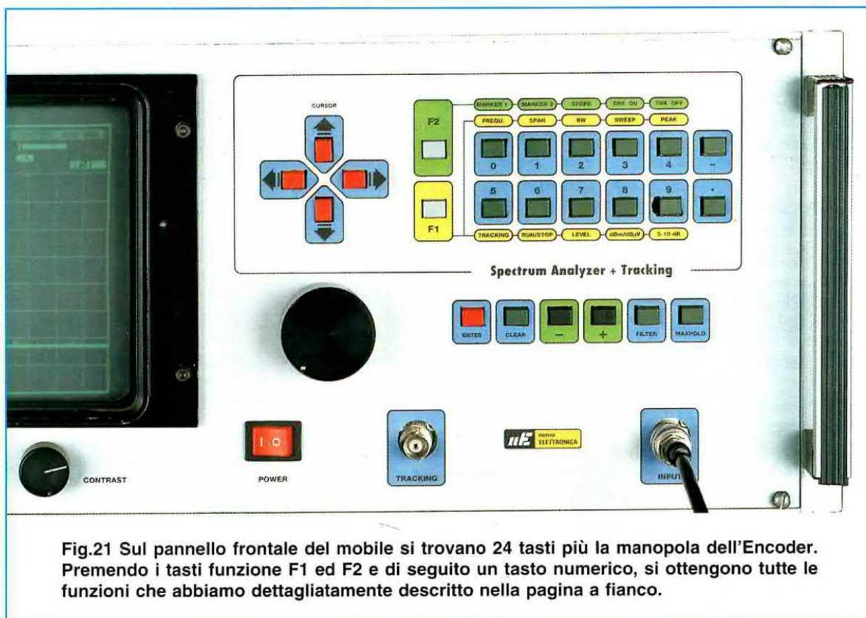
**Fig.21** Sul pannello frontale del mobile si trovano 24 tasti più la manopola dell'Encoder. Premendo i tasti funzione F1 ed F2 e di seguito un tasto numerico, si ottengono tutte le funzioni che abbiamo dettagliatamente descritto nella pagina a fianco.
