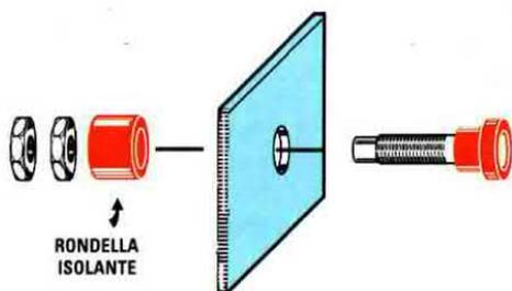
Fig.7 Prima di fissare sulla parete laterale del mobile le due bocche d'uscita per il tester, dovete sfilare dal loro corpo la rondella isolante posteriore e reinserirla dalla parte interna della scatola così da isolarle dal metallo.
