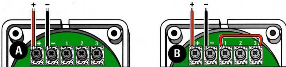
Fig.12 All'interno della scatola della sirena trovate questa morsettiera. Se lasciate scollegati i tre morsetti 1-2-3 (vedi A) ottenete un suono CONTINUO, se collegate i morsetti 1-3 (vedi B) ottenete un suono BILTONALE, mentre se collegate i morsetti 1-2 (vedi C) ottenete un suono ad IMPULSI.
