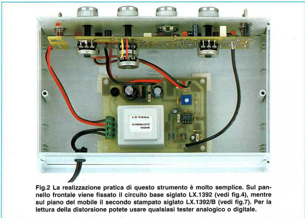
Fig.2 La realizzazione pratica di questo strumento è molto semplice. Sul pannello frontale viene fissato il circuito base siglato LX.1392 (vedi fig.4), mentre sul piano del mobile il secondo stampato siglato LX.1392/B (vedi fig.7). Per la lettura della distorsione potete usare qualsiasi tester analogico o digitale.
