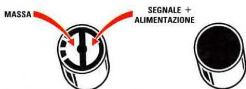
Fig.317 Prima di collegare il piccolo microfono al circuito stampato, controllate quale delle due piste è quella collegata elettricamente al metallo esterno del microfono. Questa pista è quella di Massa, l'altra è quella del segnale.
