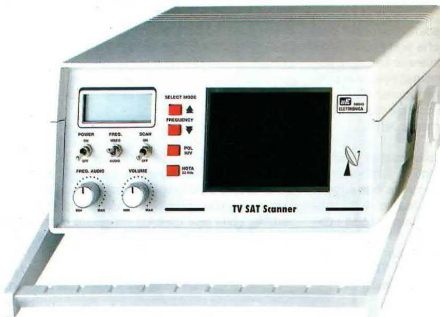
Fig.1 Sul frontale dello Scanner è presente un display LCD sul quale si può leggere la frequenza Video-Audio e un monitor LCD che permette di vedere l'immagine captata.
