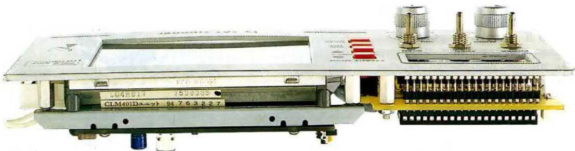
Fig.23 Per fissare il monitor LCD e la scheda LX.1415/B dovete usare i distanziatori metallici maschio-femmina che troverete nel kit (vedi disegno di fig.24).
