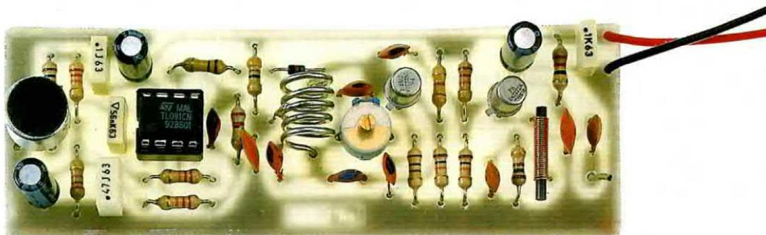
Fig.321 Foto del trasmettitore in FM. Il circuito stampato che vi forniremo risulta già forato e completo di disegno serigrafico. Per aumentare la portata, anzichè utilizzare un'antenna lunga 73-74 cm, si potrebbe utilizzare un filo lungo 220 cm pari a 3/4 di lunghezza d'onda. Se userete lunghezze diverse, irradierete meno potenza.
