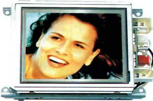
**Fig.5** Lo schermo utile del monitor LCD è di **80x65** millimetri.
