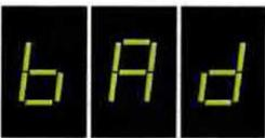
Fig.13 Se il transistor collegato alle bocche fosse difettoso, vedreste lampeggiare per pochi secondi la scritta "bAd" e poi riapparire nuovamente le tre linee di fig.10.
