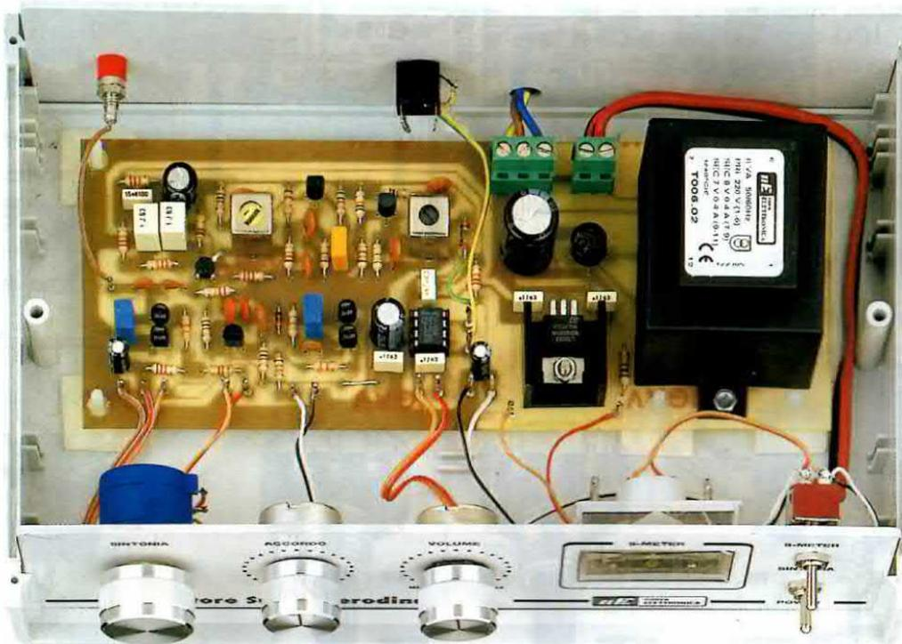
**Fig.382** Il circuito stampato va fissato all'interno del mobile con dei distanziatori plastici con base autoadesiva che innesterete nei 6 fori presenti sullo stampato. Prima di fissare i potenziometri di **Accordo** e del **Volume** sul pannello frontale, dovete accorciare i loro perni per tenere le manopole il più vicino possibile al pannello.
