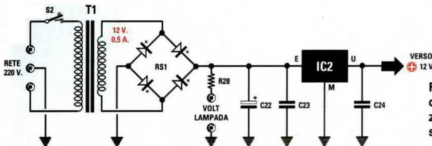
Fig.377 Schema elettrico dello stadio di alimentazione che fornisce una tensione di 12 volt.
