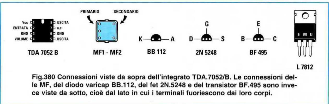
Fig.380 Connessioni viste da sopra dell'integrato TDA.7052/B. Le connessioni delle MF, del diodo varicap BB.112, del fet 2N.5248 e del transistor BF.495 sono invece viste da sotto, cioè dal lato in cui i terminali fuoriescono dai loro corpi.
