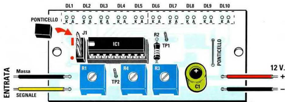
Fig.23 Per realizzare gli schemi elettrici riportati nelle figg.3-4-6-7-8 potrete utilizzare il circuito stampato LX.1439 e su questo montare tutti i componenti richiesti. In questo montaggio i trimmer R1-R3 vi serviranno per tarare il fondo scala. Se non vi interessa l'inizio scala (vedi fig.8) dovrete ruotare il cursore del trimmer R4 in modo da cortocircuitare la sua resistenza. Nel kit è inserito l'integrato LM.3914.
