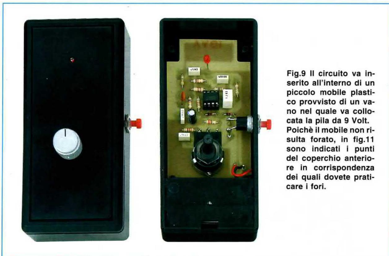
**Fig.9** Il circuito va inserito all'interno di un piccolo mobile plastico provvisto di un vano nel quale va collocata la pila da 9 Volt. Poichè il mobile non risulta forato, in fig.11 sono indicati i punti del coperchio anteriore in corrispondenza dei quali dovete praticare i fori.
