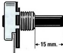
Fig.8 Prima di fissare il potenziometro, accorciate il suo perno sui 15 mm circa.
