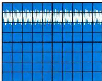
Fig.35 Se collegate l'uscita di un Generatore di Rumore, ad esempio LX.1142, direttamente all'ingresso dell'Analizzatore, sullo schermo vedrete una riga orizzontale che lo copre interamente. Poichè il Generatore di Rumore viene usato in sostituzione del Tracking, questo accessorio può essere usato anche per gli Analizzatori che ne sono sprovvisti.
