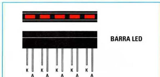
Fig.21 Tutti i terminali più Corti dei diodi led dovranno essere infilati nei fori del circuito stampato contrassegnati dalla K.
