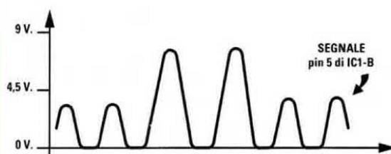
Fig.2 Il condensatore C5 e i diodi DS1-DS2 permettono di prelevare dall'uscita di IC1/A un segnale alternato che da 0 volt raggiungerà un massimo di circa 8 volt. Questo segnale, applicato sul piedino 5 di IC1/B, viene poi comparato con la tensione positiva che il potenziometro R8 applica sull'opposto piedino invertente 6.
