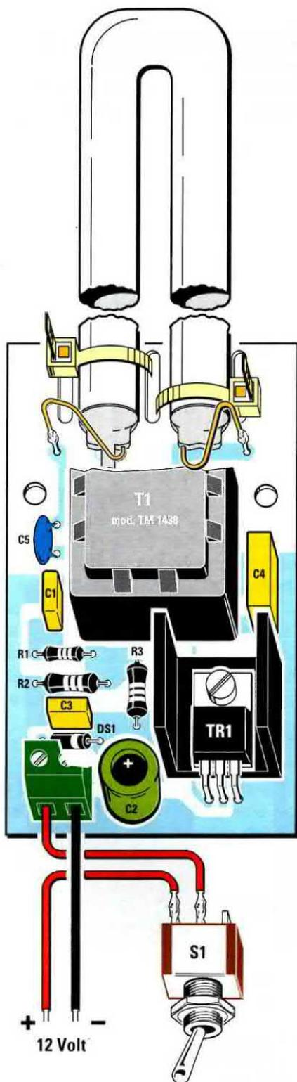
Fig.2 Disegno dello schema pratico di montaggio. La lampadina a U va fissata sul circuito stampato per mezzo delle due fascette di plastica che troverete nel kit.
