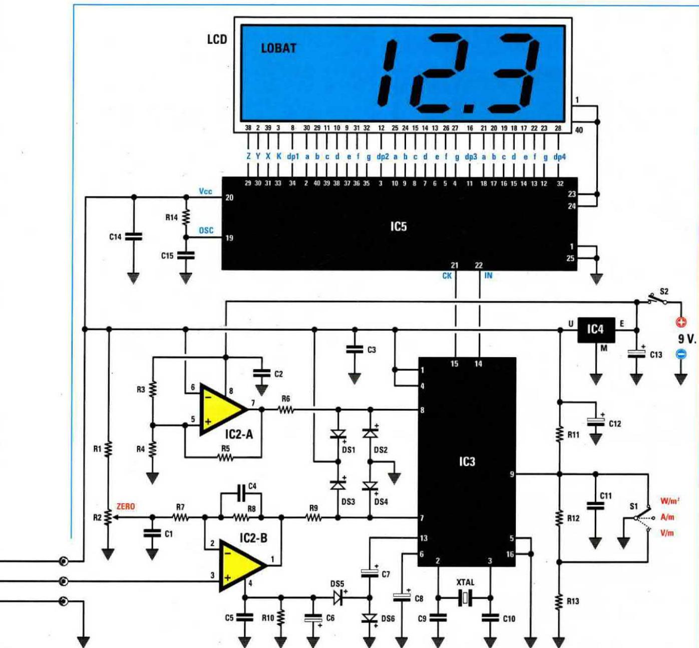
Fig.3 Schema elettrico del misuratore di elettrosmog RF. Il guadagno dello stadio IC2/B è stato calcolato per le dimensioni dell'antenna captatrice inserita nel kit. Agendo sul deviatore S1 potete misurare sia i Volt/m, che gli Amper/m ed i Watt/metroquadrato.
