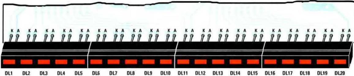
Fig.27 Anche in tutti i circuiti stampati che utilizzano 20 diodi led dovrete inserire le barre dal lato opposto a quello dei componenti, rivolgendo tutti i terminali più Corti di questi diodi, cioè i terminali K, verso sinistra.
