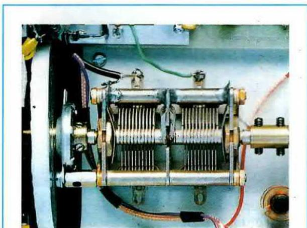
**Fig.374** In tutti i ricevitori supereterodina era presente un doppio condensatore variabile. Una sezione veniva utilizzata per sintonizzare l'emittente e l'altra per variare la frequenza dell'oscillatore locale.
