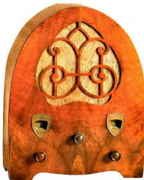
**Fig.364** Negli anni 1928-1930 apparvero i primi ricevitori supereterodina. Il mobile, sempre in legno, venne reso più elegante e la tromba venne sostituita da un altoparlante per migliorare la qualità sonora.
