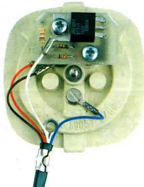
**Fig.7** Foto del circuito stampato già fissato sulla spina telefonica. Se il coperchio della spina non dovesse chiudersi, sarà sufficiente arrotondare con una lima i due spigoli superiori del circuito stampato.
