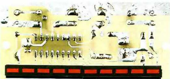
Fig.11 Conviene sempre inserire la barra dei diodi led sul retro dello stampato.
