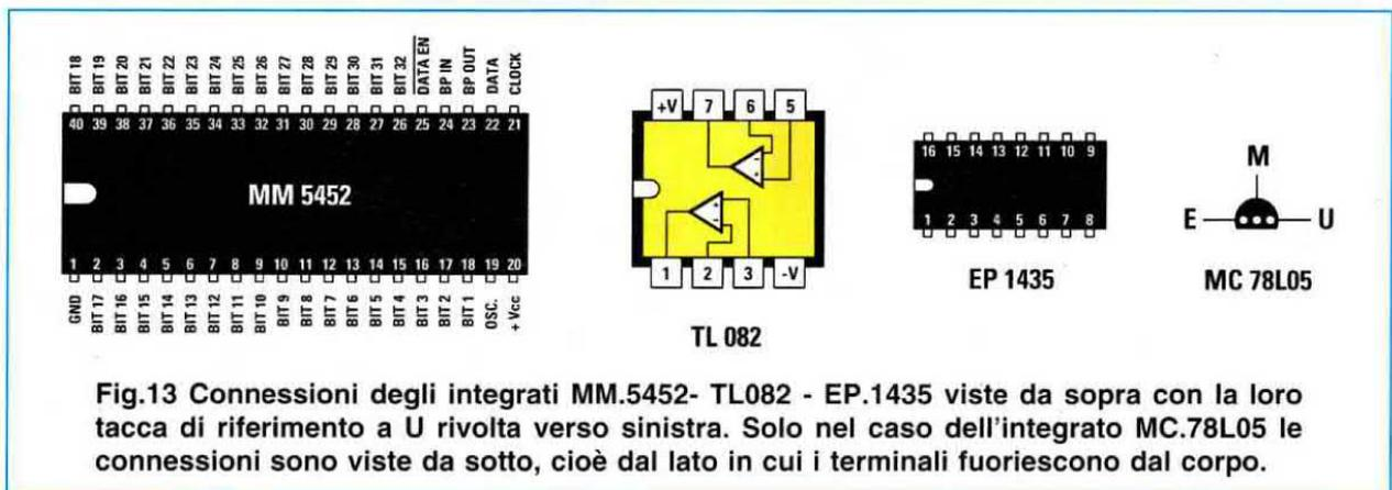
Fig.13 Connessioni degli integrati MM.5452- TL082 - EP.1435 viste da sopra con la loro tacca di riferimento a U rivolta verso sinistra. Solo nel caso dell'integrato MC.78L05 le connessioni sono viste da sotto, cioè dal lato in cui i terminali fuoriescono dal corpo.
