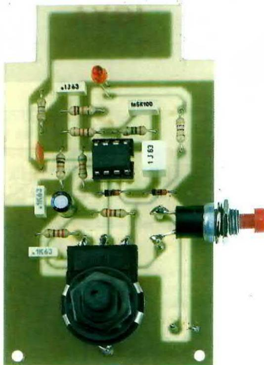
Fig.7 Ecco come si presenta a montaggio ultimato il nostro circuito Cercafili.
