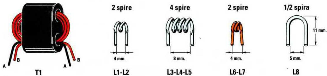
**Fig.12** Per il trasformatore T1 dovete avvolgere 1 spira per l'avvolgimento A-A e 3 spire per l'avvolgimento B-B. Per le altre bobine, osservate le figg.13-14 e leggete attentamente quanto riportato nel testo. La bobina L8 va avvolta sopra un diametro di 5 mm.
