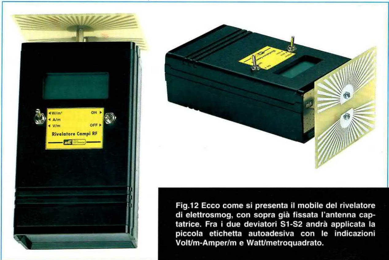
Fig.12 Ecco come si presenta il mobile del rivelatore di elettrosmog, con sopra già fissata l'antenna captatrice. Fra i due deviatori S1-S2 andrà applicata la piccola etichetta autoadesiva con le indicazioni Volt/m-Amper/m e Watt/metroquadrato.
