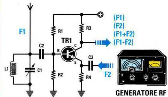
**Fig.366** Applicando sull'**Emettitore** del transistor un segnale prelevato da un **Generatore RF** esterno, sul suo **Collettore** saranno presenti ben **quattro** diverse frequenze.
