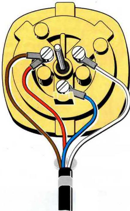
**Fig.4** Aprendo la spina di attacco del vostro telefono vedrete 4 fili collegati alle tre viti visibili in disegno. Per inserire il circuito bisogna soltanto svitare il filo di destra e collegarlo come visibile in fig.5.
