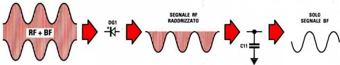
**Fig.381** Dal secondario della MF2 fuoriesce un segnale RF come visibile nel disegno di sinistra. Il diodo DG1 elimina le semionde positive. Collegando tra il diodo e la massa un condensatore da 15.000 pF, questo scaricherà a massa la sola frequenza RF perchè per i 455 KHz questa capacità si comporta come una resistenza di pochi ohm, mentre per la BF questa capacità si comporta come una resistenza da 1.000 ohm.
