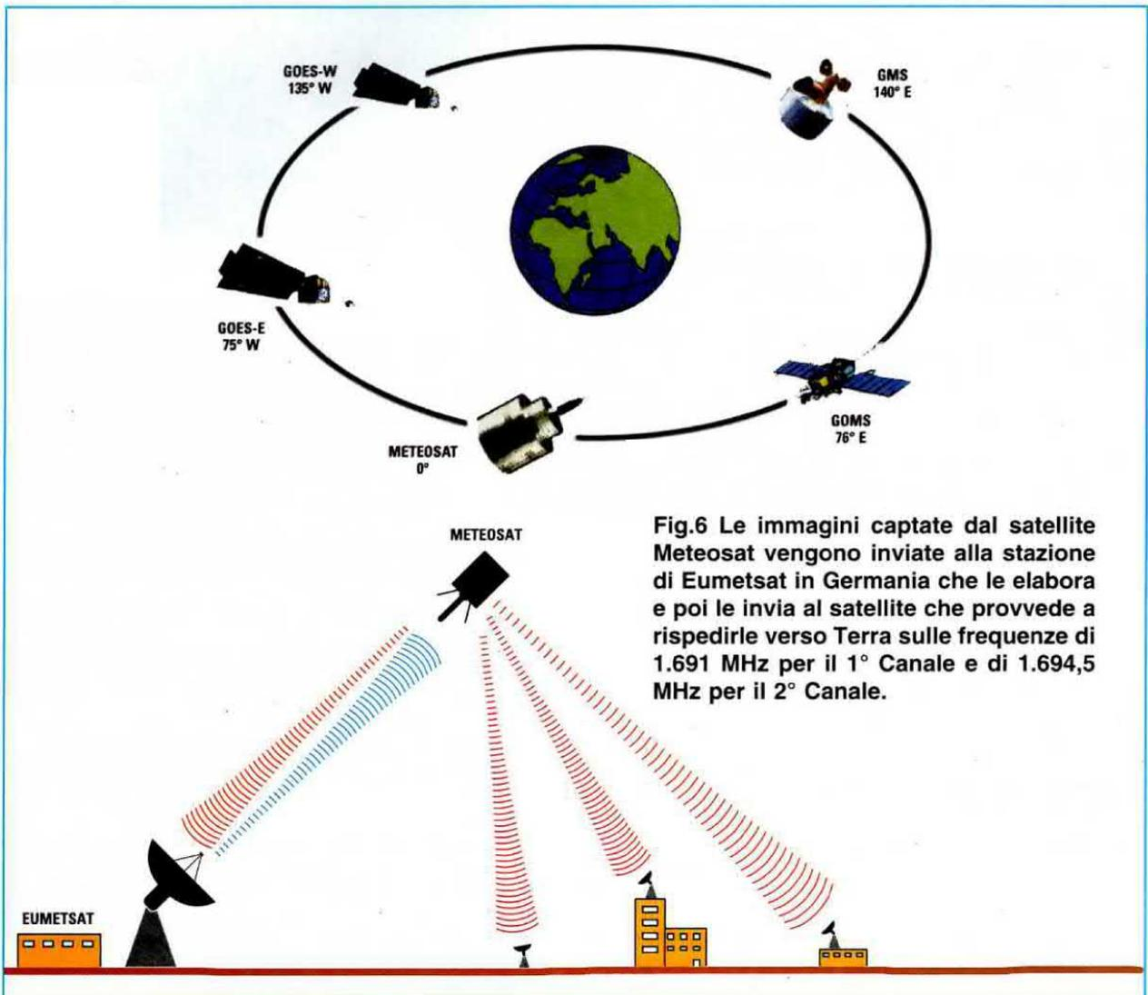
Fig.6 Le immagini captate dal satellite Meteosat vengono inviate alla stazione di Eumetsat in Germania che le elabora e poi le invia al satellite che provvede a rispedirle verso Terra sulle frequenze di 1.691 MHz per il 1° Canale e di 1.694,5 MHz per il 2° Canale.
