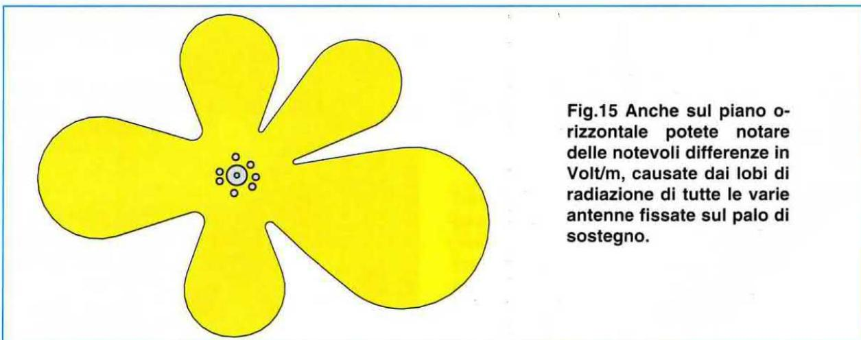
Fig.15 Anche sul piano orizzontale potete notare delle notevoli differenze in Volt/m, causate dai lobi di radiazione di tutte le varie antenne fissate sul palo di sostegno.
