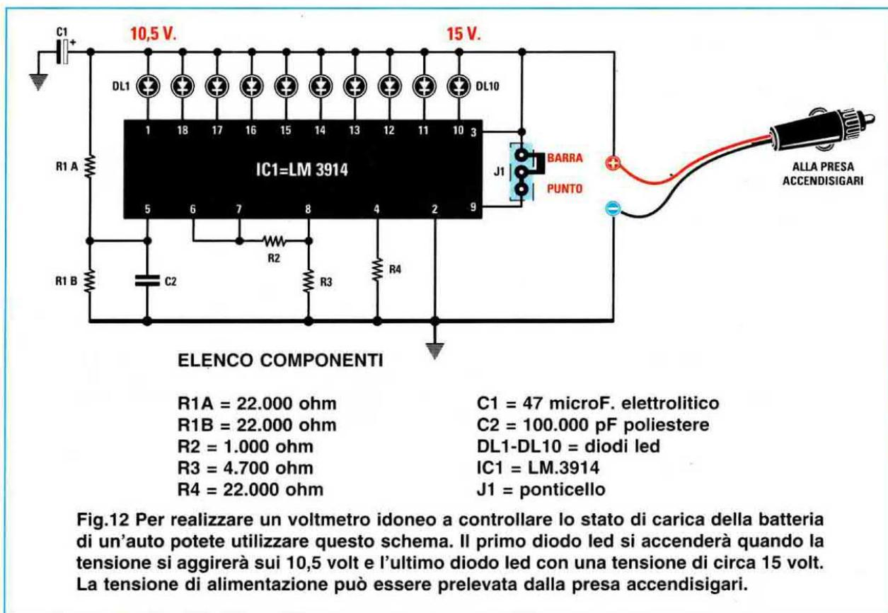
Se vogliamo ottenere una **barra** luminosa, anziché accendere singolarmente i **10 diodi** led, sarà sufficiente collegare il piedino **9** alla tensione **positiva** di alimentazione.
