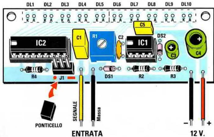
Fig.30 Per realizzare lo schema elettrico di fig.19, che utilizza due integrati LM.3915, dovete montare i componenti richiesti sul circuito stampato siglato LX.1442. Se volete che il 20° diodo led si accenda applicando sull'ingresso un segnale BF di 10 volt, tarate il trimmer R10 in modo da leggere su TP1 una tensione di 10 volt. Se volete che il 20° diodo led si accenda applicando sull'ingresso un segnale BF di 5 volt, tarate il trimmer R10 in modo da leggere su TP1 una tensione di 5 volt.
