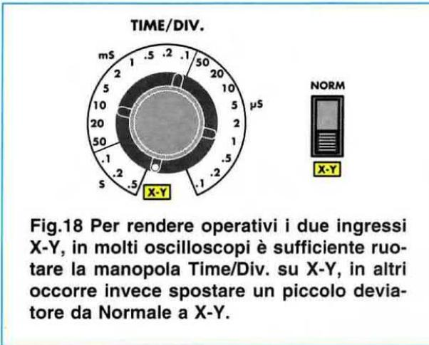
**Fig.18** Per rendere operativi i due ingressi X-Y, in molti oscilloscopi è sufficiente ruotare la manopola Time/Div. su X-Y, in altri occorre invece spostare un piccolo deviatore da Normale a X-Y.
