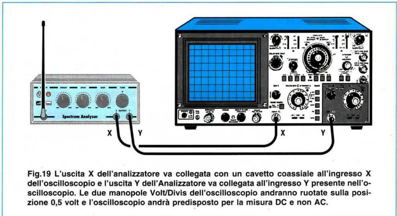
**Fig.19** L'uscita X dell'analizzatore va collegata con un cavetto coassiale all'ingresso X dell'oscilloscopio e l'uscita Y dell'Analizzatore va collegata all'ingresso Y presente nell'oscilloscopio. Le due manopole Volt/Divis dell'oscilloscopio andranno ruotate sulla posizione 0,5 volt e l'oscilloscopio andrà predisposto per la misura DC e non AC.
