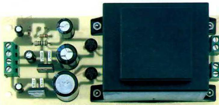
**Fig.17** Foto dello stadio di alimentazione notevolmente ridotto. Sui due integrati **IC1-IC2** non è necessario applicare nessuna aletta di raffreddamento.
