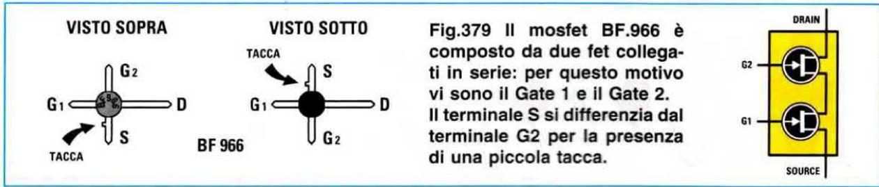
Fig.379 Il mosfet BF.966 è composto da due fet collegati in serie: per questo motivo vi sono il Gate 1 e il Gate 2. Il terminale S si differenzia dal terminale G2 per la presenza di una piccola tacca.
