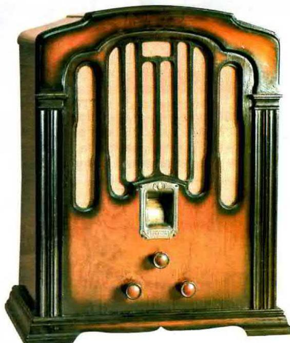
Fig.371 Le supereterodine per uso familiari del 1936 avevano tre sole manopole, una per il cambio gamma OM-OC, una per la sintonia ed una per il volume.
