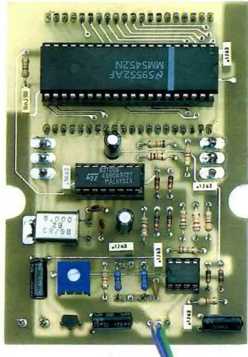
Fig.4 Schema pratico di montaggio del rivelatore di elettrosmog visto dal lato componenti. I tre fili S, M, +V, vanno collegati al modulo IC1 come visibile nel disegno riportato in fig.11.
