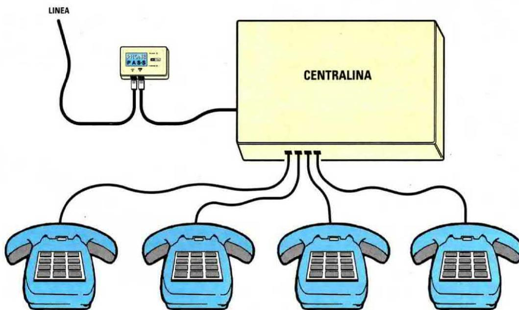
**Fig.4** Se nel vostro ufficio o nella vostra azienda è presente una centralina che attiva più apparecchi telefonici interni, il Phone-Pass andrà inserito tra la linea telefonica e la centralina, come visibile in disegno. In questo modo da qualsiasi apparecchio interno verranno effettuate delle telefonate interurbane e verso un telefono cellulare, il Phone-Pass si commuterà automaticamente sul Gestore che fa spendere di meno.
