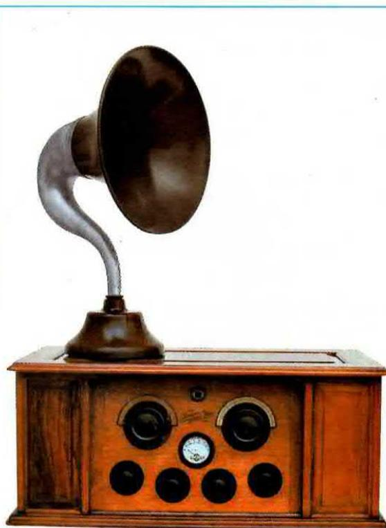
**Fig.363** Nel 1924 si pensò di abbellire questi ricevitori racchiudendoli entro dei mobili in legno. Come altoparlante si utilizzava una tromba, quindi la fedeltà sonora risultava ancora molto scadente.
