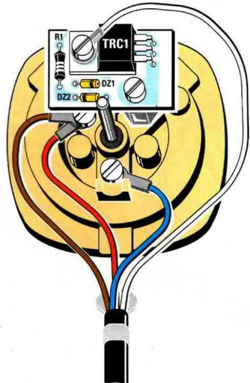
**Fig.5** Fissato il circuito stampato con sopra il diodo Triac sulla spina telefonica (vedi fig.6), dovete solo collegare il filo presente sulla destra di quest'ultima sul corpo metallico del diodo Triac.
