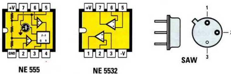
Fig.5 Connessioni dei tre integrati IC6-IC4-IC5 viste da sopra e del risonatore SAW siglato FC3 viste da sotto.
