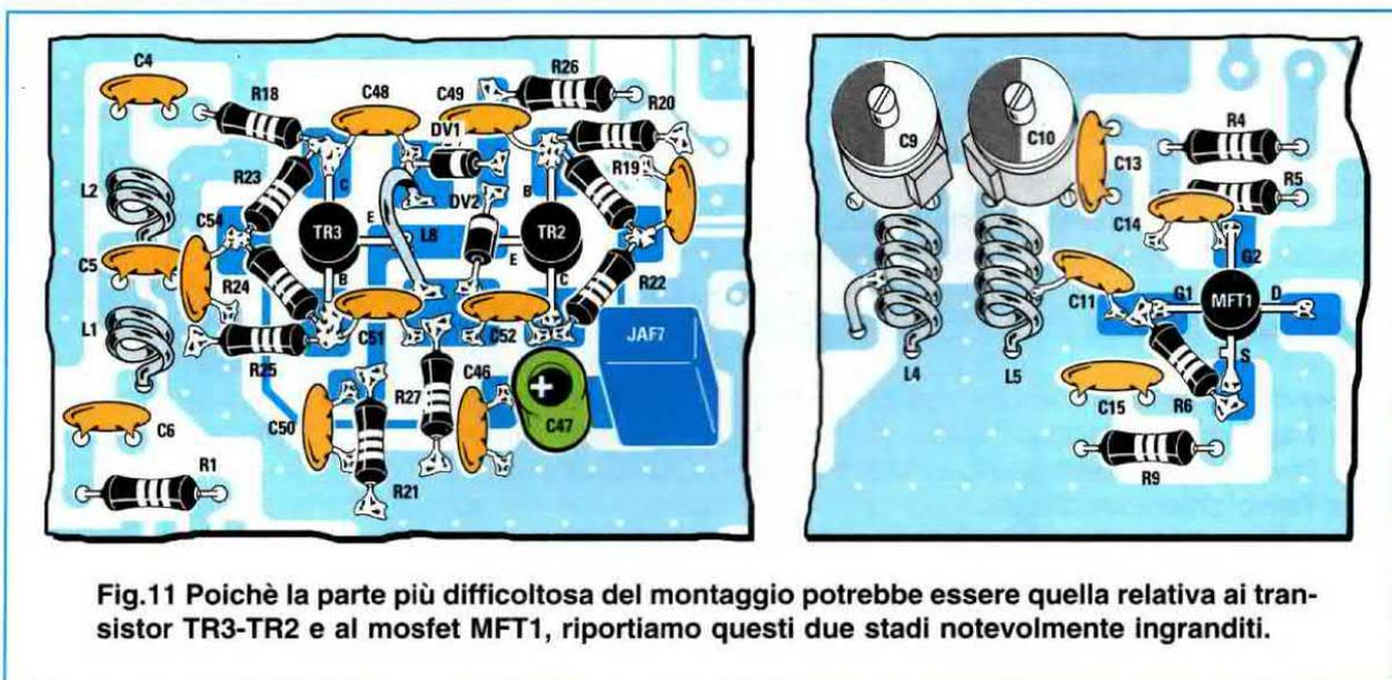
**Fig.11** Poichè la parte più difficile del montaggio potrebbe essere quella relativa ai transistor **TR3-TR2** e al mosfet **MFT1**, riportiamo questi due stadi notevolmente ingranditi.
