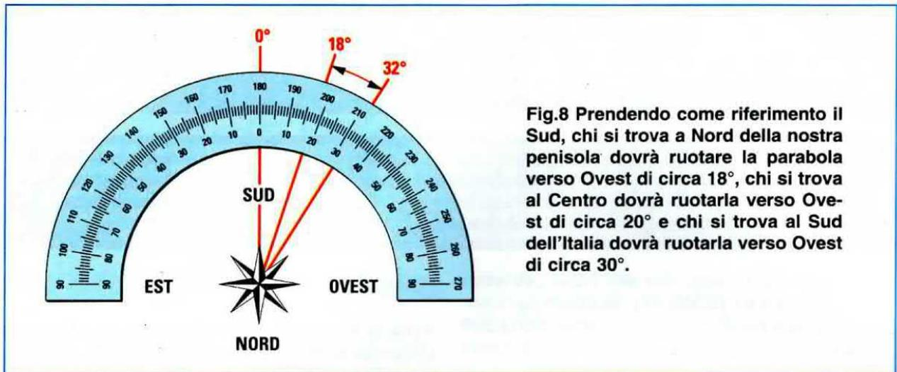
Fig.8 Prendendo come riferimento il Sud, chi si trova a Nord della nostra penisola dovrà ruotare la parabola verso Ovest di circa 18°, chi si trova al Centro dovrà ruotarla verso Ovest di circa 20° e chi si trova al Sud dell'Italia dovrà ruotarla verso Ovest di circa 30°.
