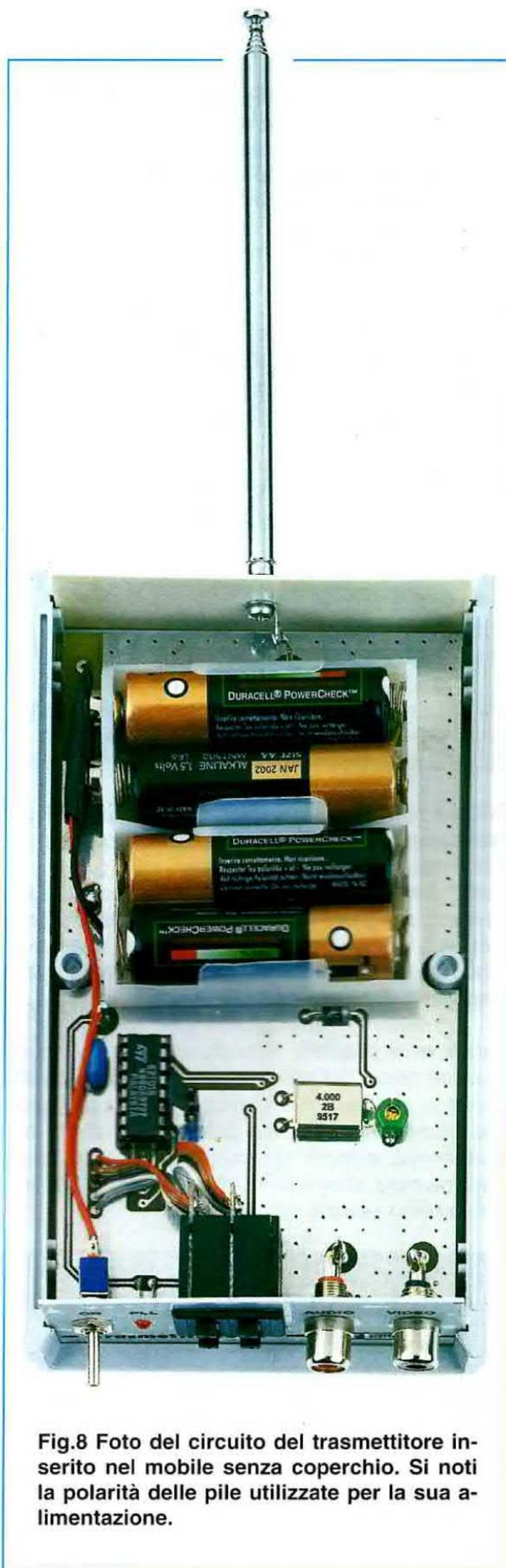
**Fig.8** Foto del circuito del trasmettore inserito nel mobile senza coperchio. Si noti la polarità delle pile utilizzate per la sua alimentazione.
