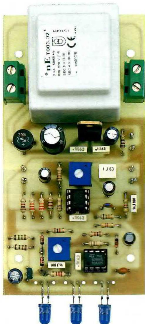
Fig.5 Foto del montaggio dello stadio trasmettente LX.1454. In basso potete vedere i tre diodi emittenti all'infrarosso.
