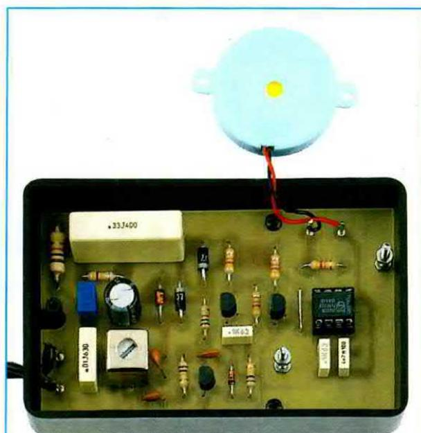
Fig.11 Prima di chiudere il mobile dovete tarare il nucleo della MF1.
