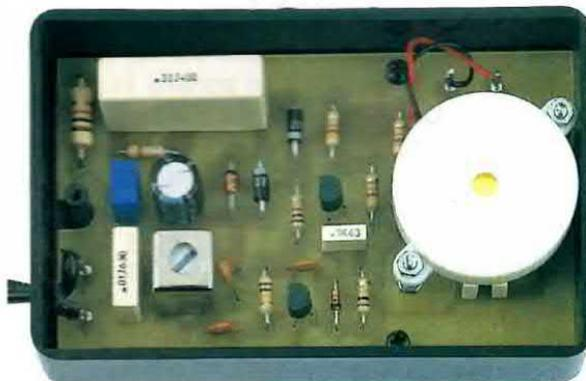
La resistenza **R1** da **470.000 ohm** applicata in parallelo al condensatore **C2**, serve per scaricare quest'ultimo non appena viene lasciato il pulsante **P1**.
