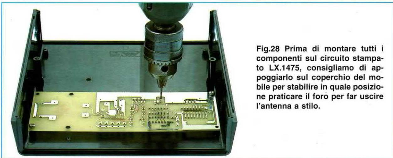
Fig.28 Prima di montare tutti i componenti sul circuito stampato LX.1475, consigliamo di appoggiarlo sul coperchio del mobile per stabilire in quale posizione praticare il foro per far uscire l'antenna a stilo.
