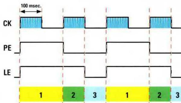
Fig.10 Quando su entrambi i piedini PE e LE giunge un livello logico 1 (fase 1) nei contatori viene caricato il "peso" binario dei dip-switches. Quando sul solo piedino PE giunge un livello logico 0 (fase 2), tutti i contatori vengono abilitati al conteggio. Quando su entrambi i piedini PE-LE giunge un livello logico 0 (fase 3), il valore della frequenza viene trasferito sui display.
