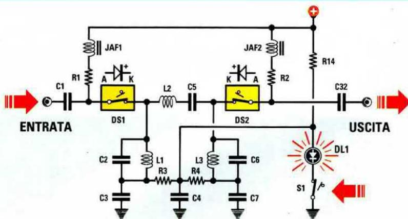
Fig.3 Quando cortocircuiterete a massa il diodo led DL1, subito scorrerà una corrente anche nei diodi schottky DS1-DS2 che, portandosi in conduzione, faranno passare il segnale RF attraverso il filtro Passa-Banda selezionato.
