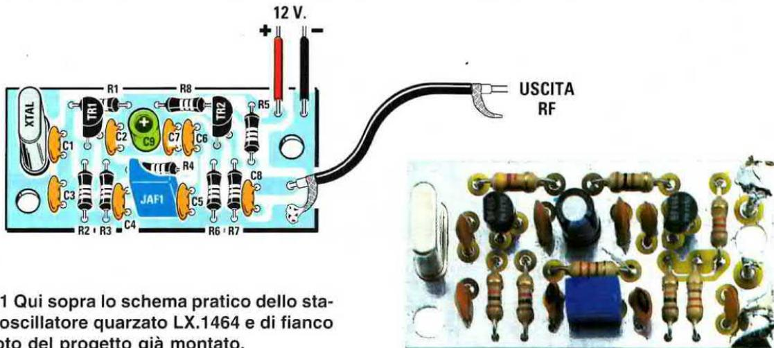
Fig.1 Qui sopra lo schema pratico dello stadio oscillatore quarzato LX.1464 e di fianco la foto del progetto già montato.
