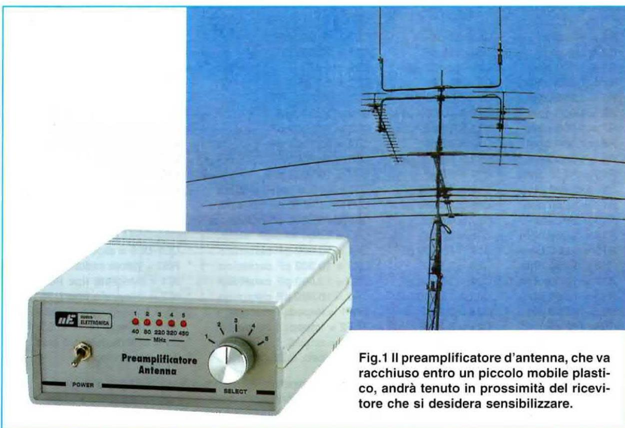
Fig.1 Il preamplificatore d'antenna, che va racchiuso entro un piccolo mobile plastico, andrà tenuto in prossimità del ricevitore che si desidera sensibilizzare.
