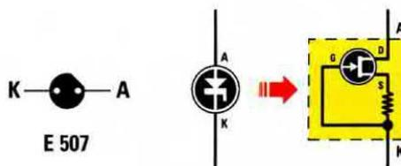
**Fig.4** Connessioni viste da sotto del diodo stabilizzatore di corrente **DZC1** (**E.507**). Questo diodo provvede a far scorrere sugli Emettitori di **TR1-TR2** una corrente stabilizzata e costante di **2 milliamper**.
