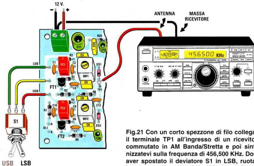
Fig.21 Con un corto spezzone di filo collegate il terminale TP1 all'ingresso di un ricevitore commutato in AM Banda/Stretta e poi sintonizzatevi sulla frequenza di 456,500 KHz. Dopo aver spostato il deviatore S1 in LSB, ruotate lentamente il nucleo della MF1 fino a far deviare verso il massimo la lancetta dell'S-Meter.
