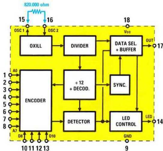
Fig.12 Schema a blocchi dell'Encoder HT.6014 che, inserito nel trasmettitore, permette di codificare gli impulsi da inviare al ricevitore spostando una o più leve del dip-switch S1.
