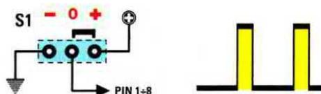
Fig.10 Posizionando una sola leva del dip-switch S1 verso il segno +, si ottiene una chiave con due impulsi stretti.
