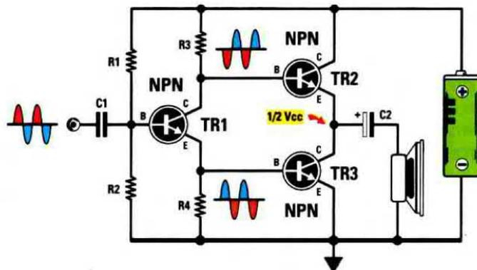
Poichè i transistor **TR2-TR3** risultano collegati in **serie**, sulla loro giunzione **Emettitore/Collettore** ci ritroveremo una tensione pari alla **metà** di quella di alimentazione, quindi per evitare che questa si scarichi a **massa** attraverso l'altoparlante, dovremo collegare quest'ultimo ai due transistor sempre tramite un **condensatore elettrolitico**.
