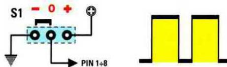
Fig.11 Posizionando una sola leva del dip-switch S1 verso il segno -, si ottiene una chiave con due impulsi larghi.
