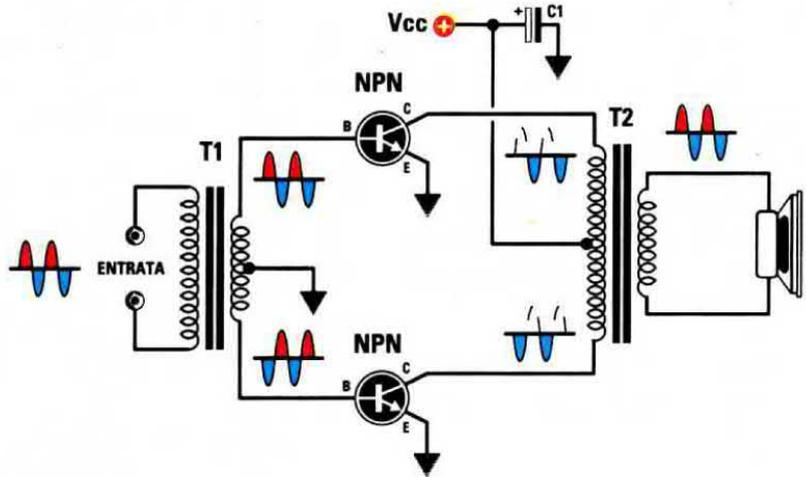
Poichè i due Collettori dei transistor sono collegati ad un trasformatore d'uscita provvisto di una presa centrale (vedi T2), dal suo secondario è possibile prelevare una **sinusoide** completa.
