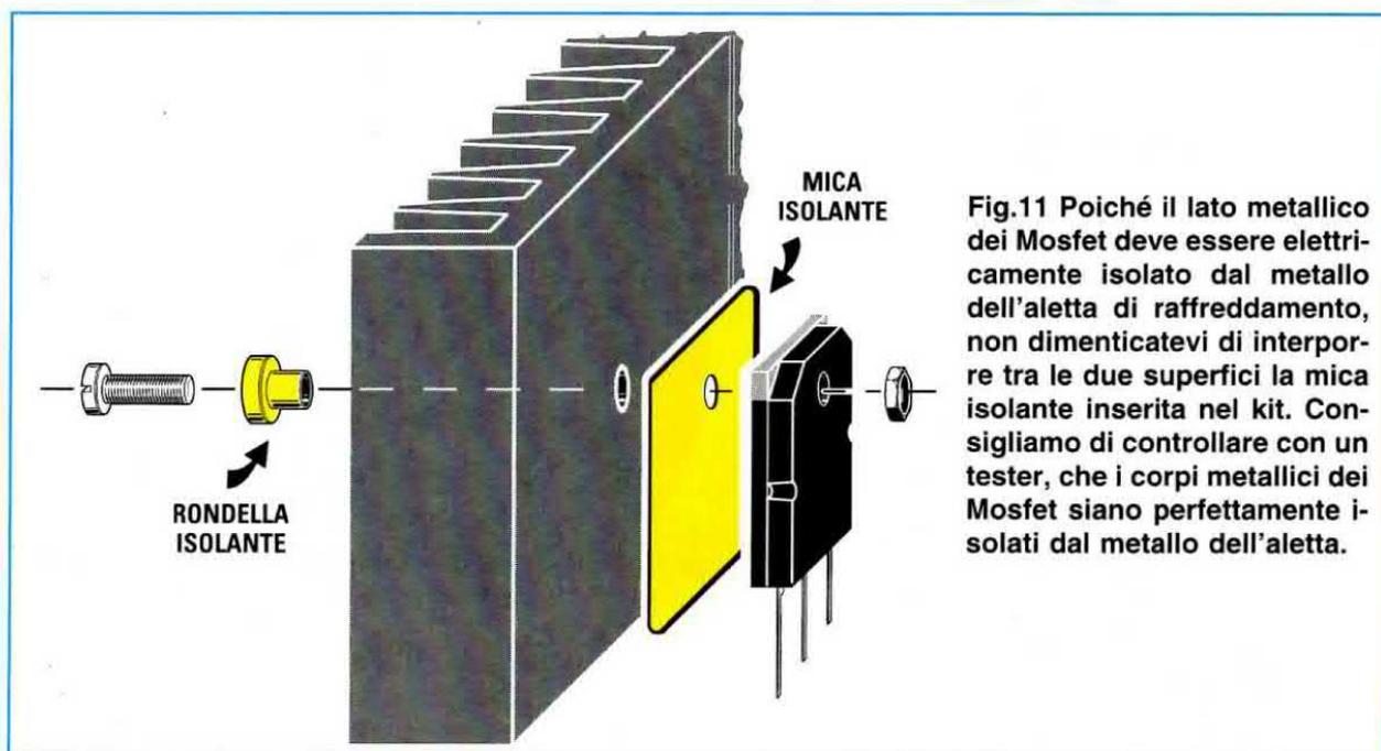
**Fig.11** Poiché il lato metallico dei Mosfet deve essere elettricamente isolato dal metallo dell'aletta di raffreddamento, non dimenticatevi di interporre tra le due superfici la mica isolante inserita nel kit. Consigliamo di controllare con un tester, che i corpi metallici dei Mosfet siano perfettamente isolati dal metallo dell'aletta.
