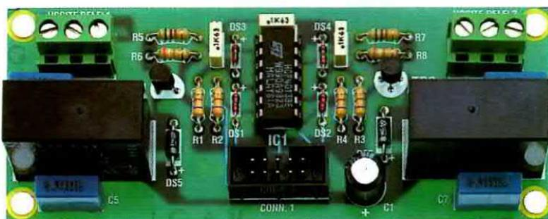
Fig.30 Foto della scheda siglata LX.1411 che utilizza 2 relè. Lo schema elettrico e il pratico sono riprodotti nelle figg.31-33.
