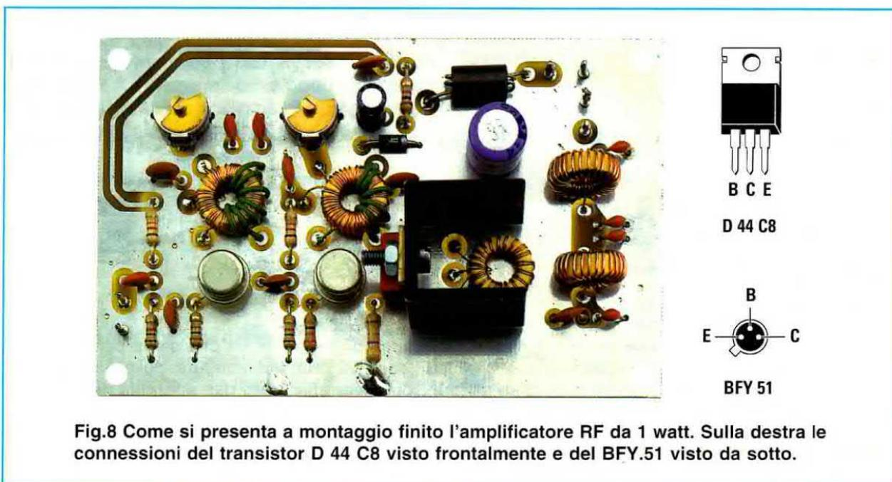
Fig.8 Come si presenta a montaggio finito l'amplificatore RF da 1 watt. Sulla destra le connessioni del transistor D 44 C8 visto frontalmente e del BFY.51 visto da sotto.
