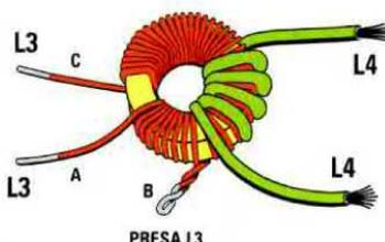
Fig.5 Per la bobina L3 avvolgete 45 spire totali con una presa alla 10° spira. Per la bobina L4 avvolgete 4 spire. Leggete il testo per conoscere il numero delle spire da avvolgere per la gamma dei 7 MHz.
