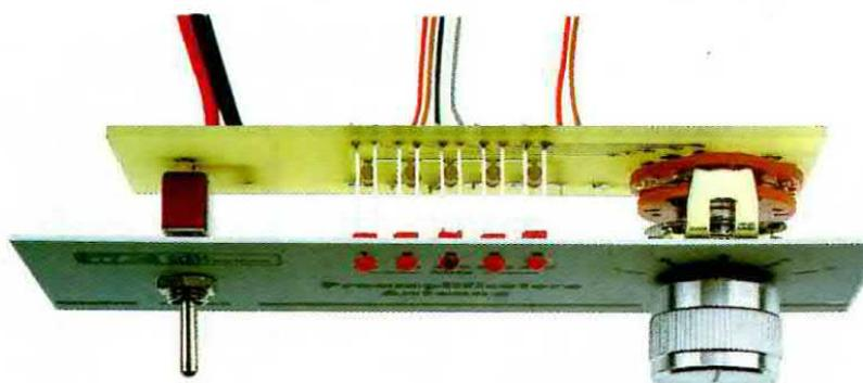
Fig.11 In questa foto, lo stampato LX.1467/B, già fissato sul pannello frontale del mobile.
