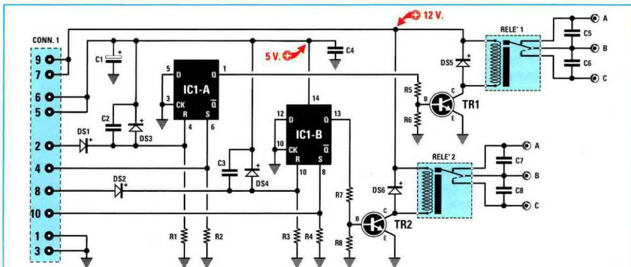
Fig.31 Schema elettrico del circuito LX.1411 che utilizza due relè. Premendo il pulsante P1 del trasmettitore si eccita il Relè 2 che rimarrà sempre eccitato fino a quando non verrà premuto il pulsante P2. Se volete eccitare il Relè 1 dovete premere il pulsante P3, mentre se volete diseccitarlo dovete premere il pulsante P4.
