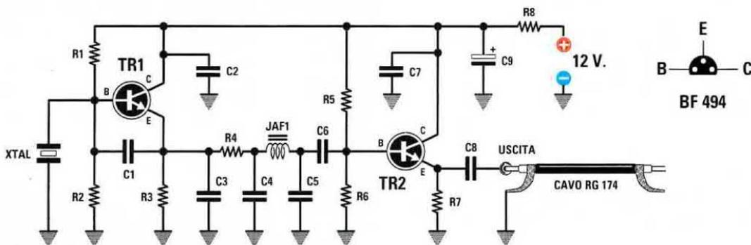
Fig.2 Schema elettrico dello stadio oscillatore e connessioni viste da sotto del transistor BF.494. Se in questo circuito sostituite il quarzo da 3,2 MHz con uno da 6,5 MHz, dovrete sostituire anche i valori dei condensatori C4-C5 e dell'impedenza JAF1.
