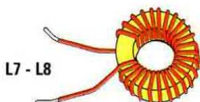
Fig.6 Per le due bobine L7-L8 avvolgete 26 spire, se il circuito viene utilizzato per la gamma dei 3,5 MHz, e 20 spire se invece lo usate per la gamma dei 7 MHz.
