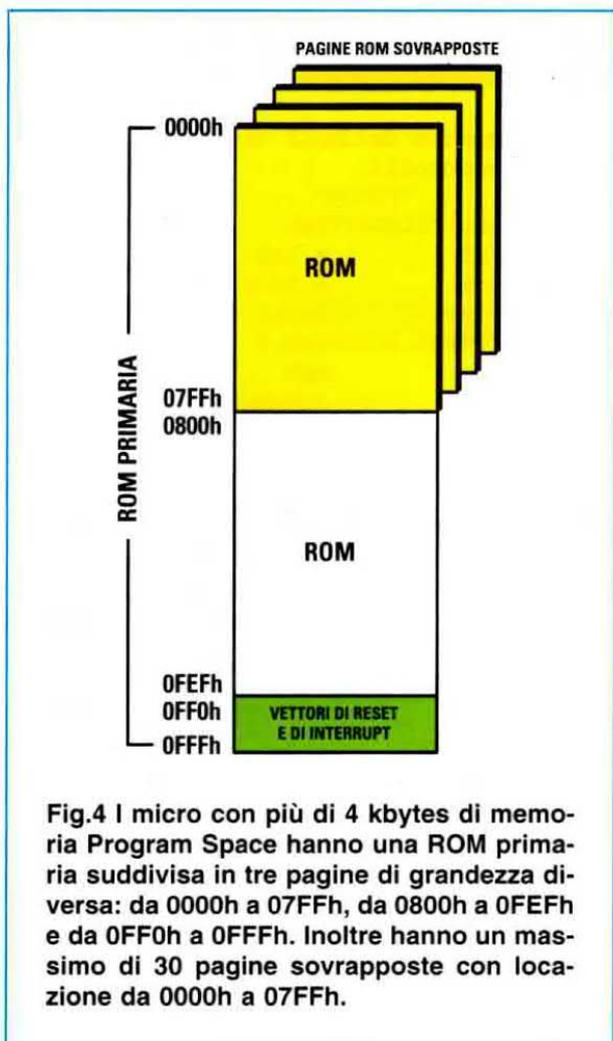
Fig.4 I micro con più di 4 kbytes di memoria Program Space hanno una ROM primaria suddivisa in tre pagine di grandezza diversa: da 0000h a 07FFh, da 0800h a 0FEFh e da 0FF0h a 0FFFh. Inoltre hanno un massimo di 30 pagine sovrapposte con locazione da 0000h a 07FFh.
