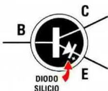
Fig.502 Con i valori di 56-47-39 kilohm, la tensione rimane fissa su 0,65 volt perchè la giunzione Base/Emettitore di un transistor si comporta come se al suo interno fosse presente un diodo al silicio e poichè questo inizia a condurre quando si superano gli 0,65 volt, anche se il partitore R1-R2 fornisce più tensione questa si stabilizzerà su 0,65 volt.
