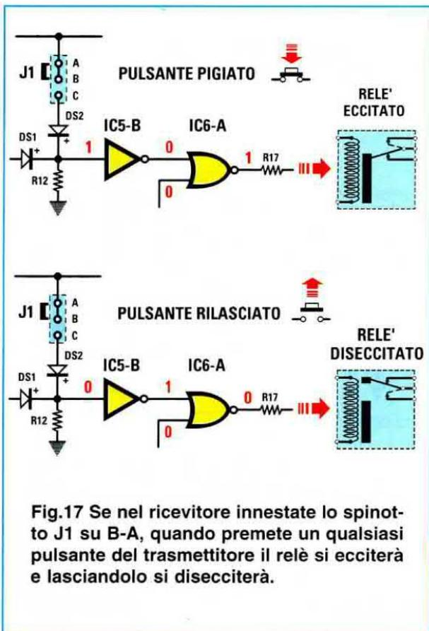
Fig.17 Se nel ricevitore innestate lo spinotto J1 su B-A, quando premete un qualsiasi pulsante del trasmettitore il relè si ecciterà e lasciandolo si disecciterà.
