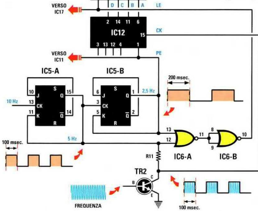
Fig.8 Le onde quadre dei 5 Hz e 2,5 Hz che entrano nel Nor IC6/A permettono di ottenere in uscita dal Nor IC6/B dei livelli logici 1-0 (figg.9-10) che vanno a pilotare il piedino LE di tutte le decodifiche.
