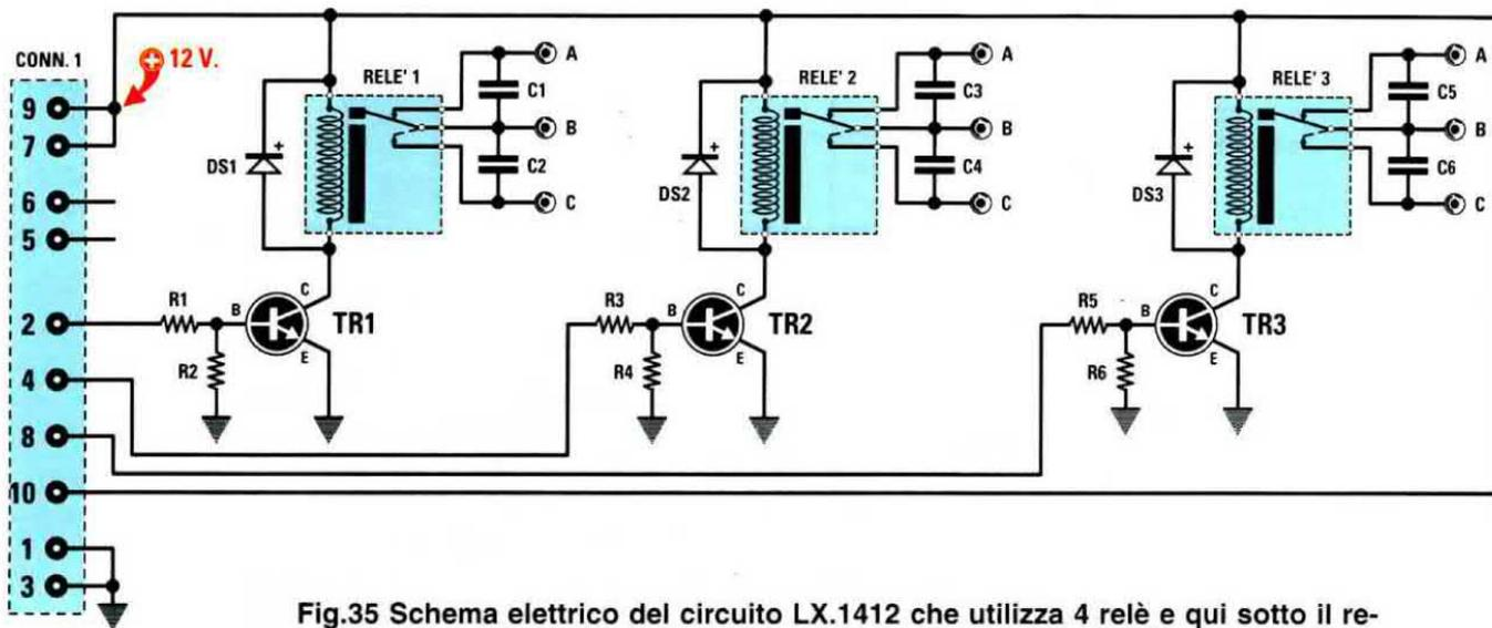
Fig.35 Schema elettrico del circuito LX.1412 che utilizza 4 relè e qui sotto il relativo schema pratico di montaggio. Premendo i pulsanti P1-P2-P3-P4 del trasmettitore in questa scheda si ecciteranno i Relè 4-3-2-1.
