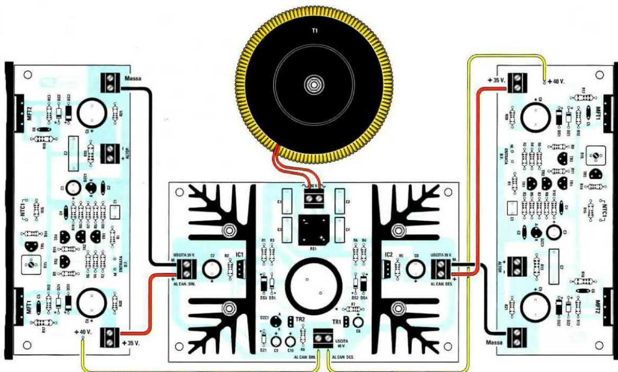
**IC2** sulle due alette di raffreddamento a forma di **V** che appoggerete sul circuito stampato tenendole bloccate con due viti per evitare che muovendosi si possano rompere i terminali dei due integrati.
