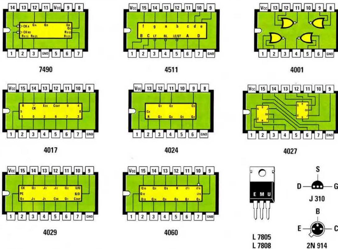
Fig.19 Connessioni di tutti gli integrati (esclusi il 4060 e il 4024) viste da sopra e con la loro tacca di riferimento a U rivolta verso sinistra. Le connessioni del fet J.310 e del transistor 2N914 sono invece viste da sotto.
