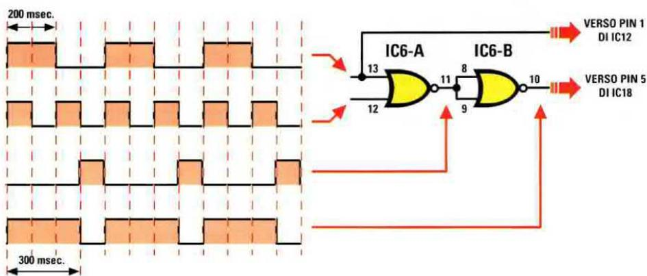
Fig.9 La tavola della verità di una porta Nor riportata sulla sinistra, permette di capire quali onde quadre fuoriescono dai piedini d'uscita del Nor IC6/A e da quelli del Nor IC6/B configurato come inverter. Quando i due ingressi 13-12 di IC6/A sono a livello logico 1-1 oppure 1-0 o 0-1, sull'uscita è presente sempre un livello logico 0. Solo quando i due ingressi sono a livello logico 0-0, l'uscita si commuta sul livello logico 1.
