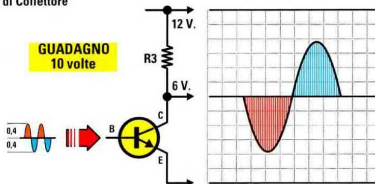
Fig.511 Per far lavorare un transistor in "classe A" dovremo polarizzare la sua Base in modo che, in assenza di segnale, sul Collettore risulti presente metà tensione di alimentazione. Quando sulla Base applicheremo un segnale alternato, in presenza delle semionde Negative il transistor assorbirà meno corrente e in presenza delle semionde Positive assorbirà più corrente.
