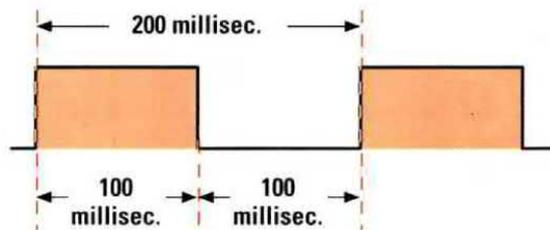
Fig.7 Poichè dal piedino 15 del flip/flop IC5/A esce un'onda quadra con una frequenza di 5 Hertz, un ciclo completo si compie in un tempo di 200 millisecondi. Con un duty-cycle del 50% l'onda quadra rimane a livello logico 1 per 100 millisecondi e a livello logico 0 per altri 100 millisecondi.
