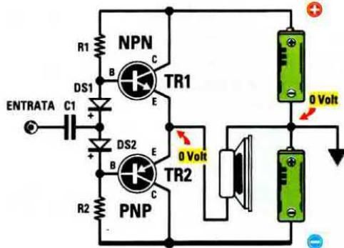
**Fig.528** Uno stadio finale che utilizza un transistor **NPN** e un **PNP** collegati in serie viene chiamato a **Simmetria Complementare**. Questo stadio finale si alimenta normalmente con una tensione **Duale**. L'altoparlante va collegato direttamente sugli **Emettitori** senza condensatore.
