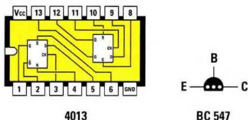
Fig.32 Connessioni dell'integrato 4013 viste da sopra e con la tacca di riferimento a U rivolta a sinistra. Le connessioni del transistor BC.547 sono invece viste da sotto.
