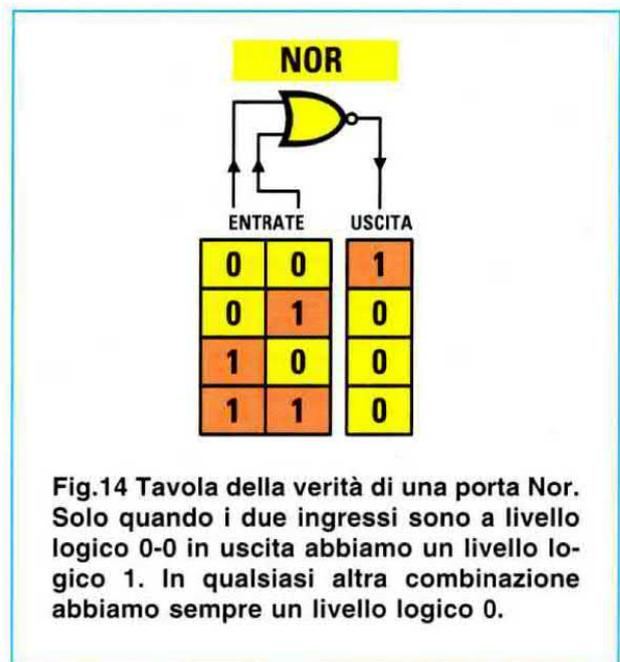
**Fig.14 Tavola della verità di una porta Nor. Solo quando i due ingressi sono a livello logico 0-0 in uscita abbiamo un livello logico 1. In qualsiasi altra combinazione abbiamo sempre un livello logico 0.**
