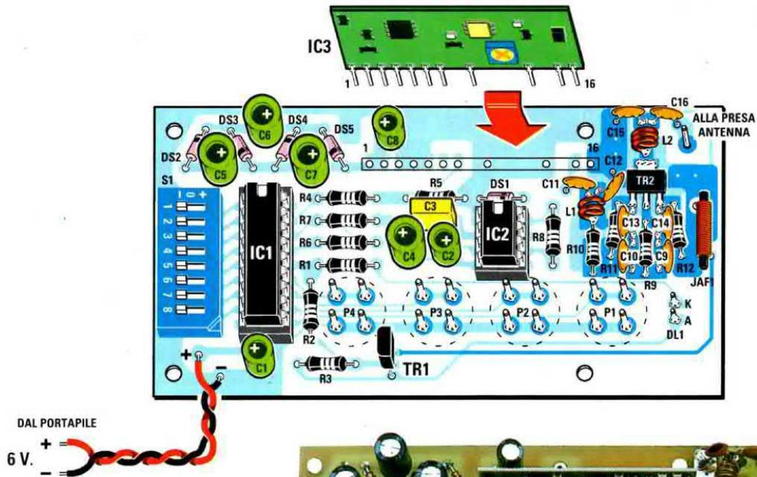
Fig.19 In alto, lo schema pratico di montaggio del trasmettitore e di lato la sua foto. Il lato leggermente arrotondato del transistor TR1 va rivolto a sinistra.
