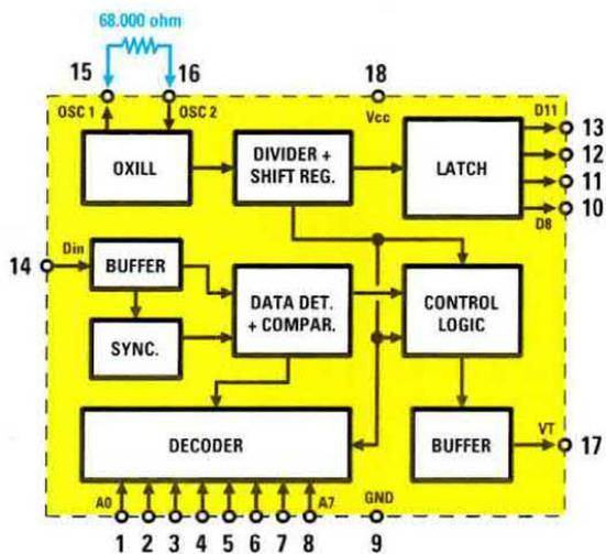
Fig.13 Schema a blocchi del Decoder HT.6034 che, inserito nel ricevitore, eccita i relè solo se le leve del suo dip-switch risultano disposte in modo identico a quelle del trasmettitore.
