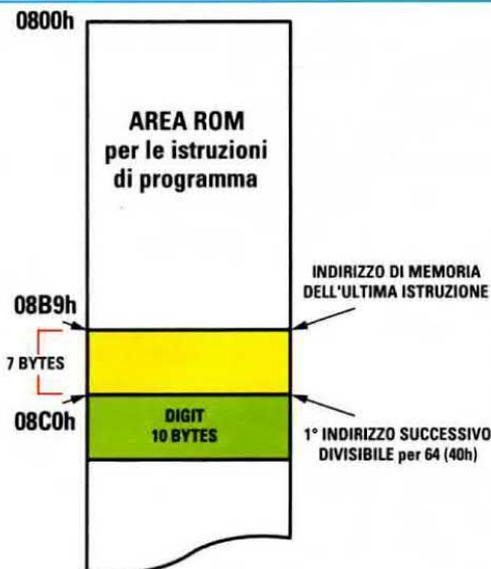
Fig.14 Se la differenza tra la prima locazione di memoria ROM divisibile per 64 e la locazione dell'ultima istruzione è minore dell'area window section, i dati vengono inseriti dopo questa locazione.
