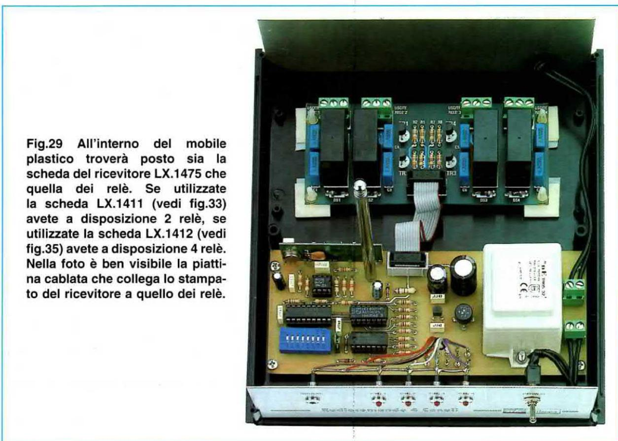
Fig.29 All'interno del mobile plastico troverà posto sia la scheda del ricevitore LX.1475 che quella dei relè. Se utilizzate la scheda LX.1411 (vedi fig.33) avete a disposizione 2 relè, se utilizzate la scheda LX.1412 (vedi fig.35) avete a disposizione 4 relè. Nella foto è ben visibile la piastrina cablata che collega lo stampato del ricevitore a quello dei relè.
