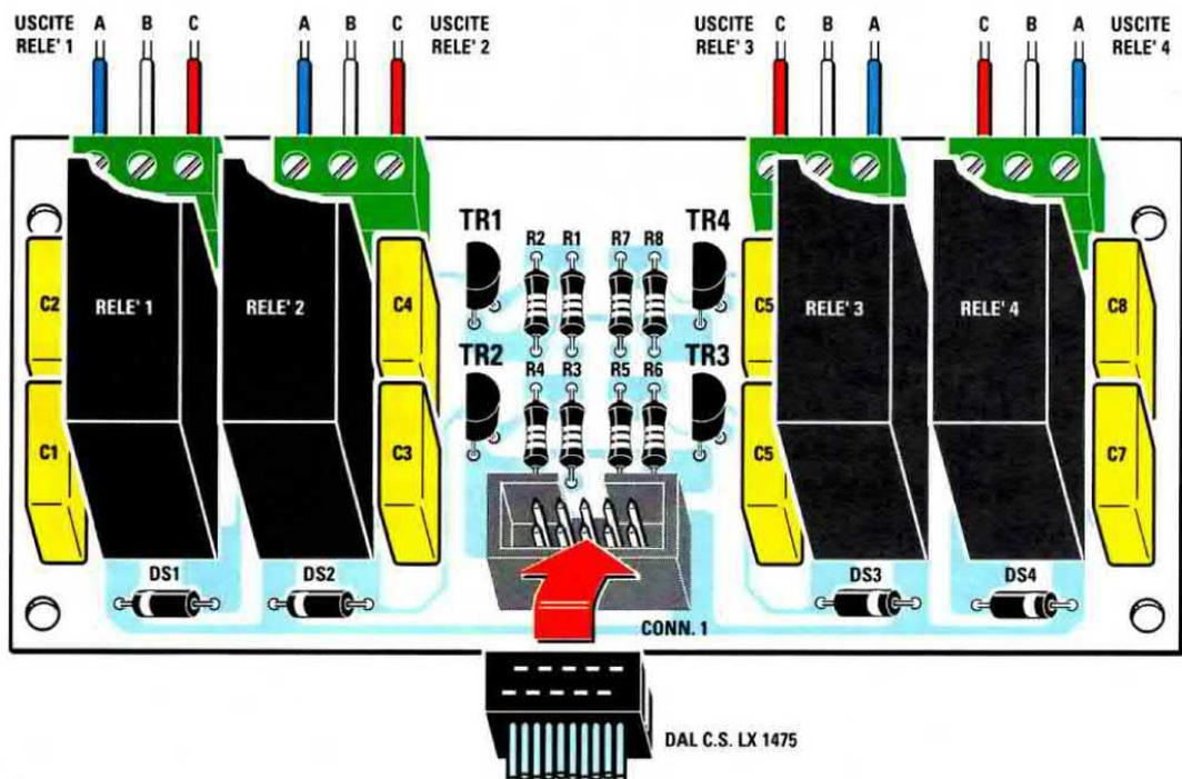
che, giungendo sulla **Base** del transistor **TR3**, lo porterà in conduzione e di conseguenza si ecciterà il **relè 3**.
