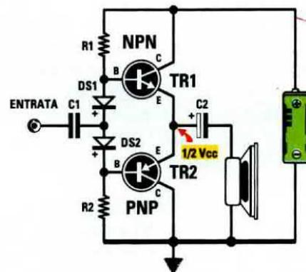
**Fig.529** Uno stadio finale a **Simmetria Complementare** si può alimentare anche con una tensione **Singola** ma poichè sui due **Emettitori** è presente una tensione pari alla metà di quella di alimentazione, l'altoparlante va collegato tramite un **condensatore elettrolitico**.
