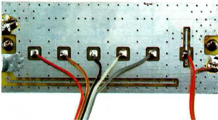
**Fig.6** Sulle 5 piste in rame presenti sul lato opposto del circuito SMD, dovete saldare i fili che partono dallo stampato del commutatore S1 (vedi fig.9).
