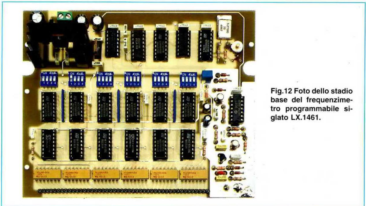
Fig.12 Foto dello stadio base del frequenzimetro programmabile siglato LX.1461.
