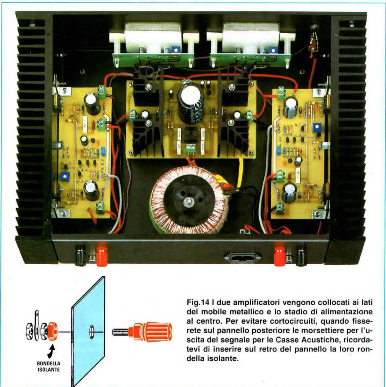
Fig.14 I due amplificatori vengono collocati ai lati del mobile metallico e lo stadio di alimentazione al centro. Per evitare cortocircuiti, quando fissate sul pannello posteriore le morsettiere per l'uscita del segnale per le Casse Acustiche, ricordatevi di inserire sul retro del pannello la loro rondella isolante.
