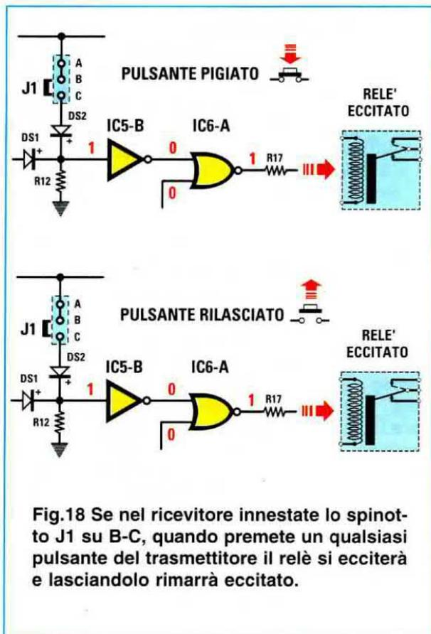
Fig.18 Se nel ricevitore innestate lo spinotto J1 su B-C, quando premete un qualsiasi pulsante del trasmettitore il relè si ecciterà e lasciandolo rimarrà eccitato.
