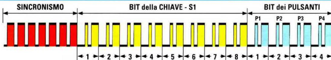
Fig.7 Dal piedino 17 dell'Encoder HT.6014 (vedi fig.12) inserito nel trasmettitore, fuoriescono gli impulsi della Chiave. I primi bit di colore Rosso sono gli impulsi di Sincronismo, gli impulsi successivi di colore Giallo sono quelli impostati tramite il dip-switch S1 e gli ultimi impulsi di colore Blu sono quelli dei pulsanti P1-P2-P3-P4.
