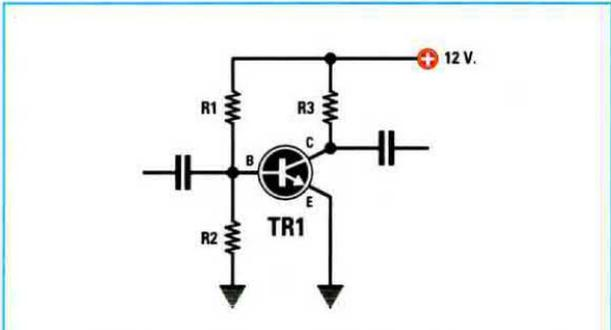
Fig.494 Le resistenze R1-R2 collegate alla Base di un transistor servono per poterlo fare lavorare in "classe A".
