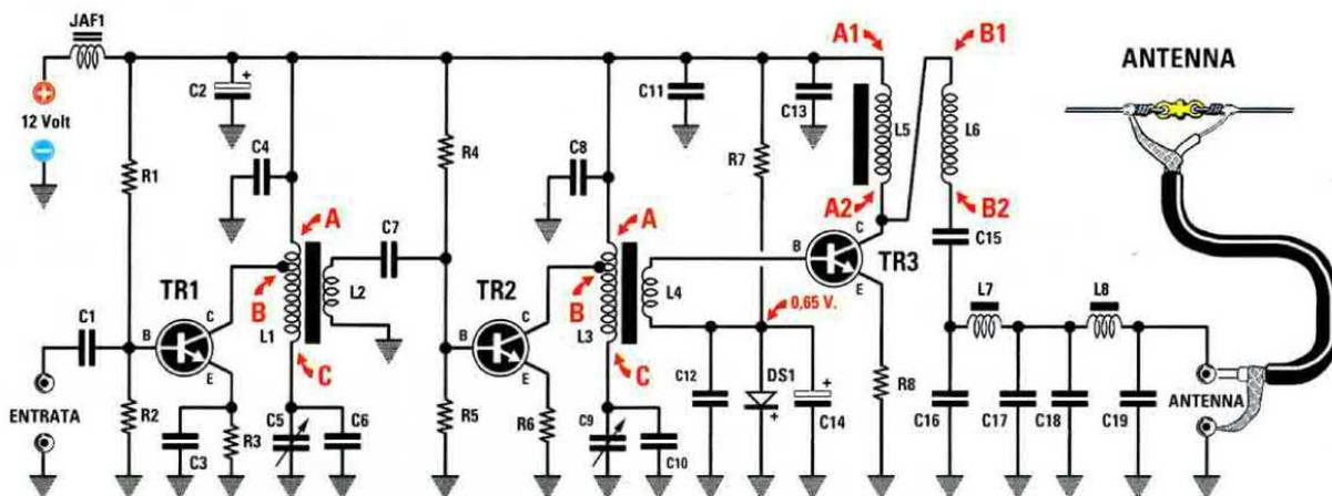
**Fig.3** Schema elettrico dello stadio amplificatore RF in grado di erogare 1 watt. Per realizzare le bobine toroidali leggete l'articolo e guardate le figg.4-5-6-7. Tutte le resistenze utilizzate in questo circuito sono da 1/4 di watt ad esclusione della sola R8.
