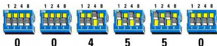
Fig.16 Per sommare un valore MF di 455 KHz dovete disporre le leve dei dip-switches come visibile nel disegno.
