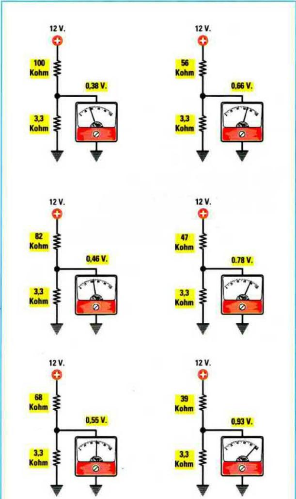
Fig.495 Se scollegiamo queste resistenze dalla Base del transistor e sulla loro giunzione applichiamo un tester, rileveremo una tensione che risulterà inversamente proporzionale al valore della R1. Tenendo fisso il valore della R2 e variando il valore della R1, sul tester leggeremo le tensioni indicate nei disegni.
