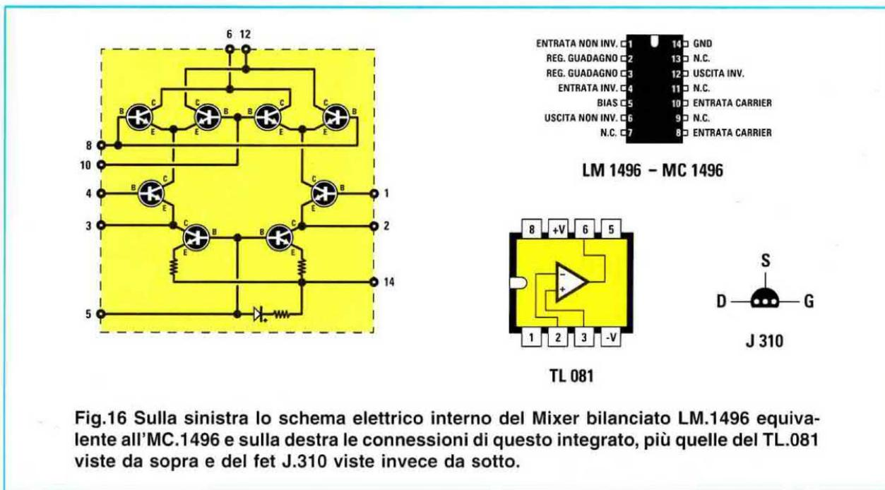
Fig.16 Sulla sinistra lo schema elettrico interno del Mixer bilanciato LM.1496 equivalente all' MC.1496 e sulla destra le connessioni di questo integrato, più quelle del TL.081 viste da sopra e del fet J.310 viste invece da sotto.
