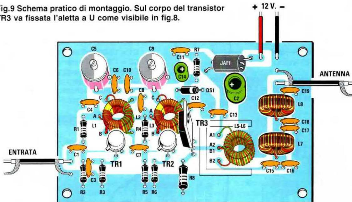
di pazienza, avvolgetelo all'interno del nucleo toroidale (vedi fig.4). Il capo d'inizio, che abbiamo chiamato **A**, andrà collegato alla tensione **positiva** dei **12 volt** (vedi fig.3).
