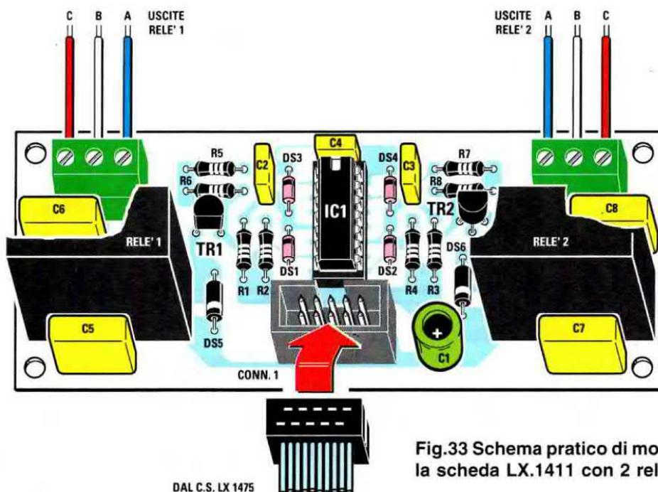
Fig.33 Schema pratico di montaggio della scheda LX.1411 con 2 relè.
