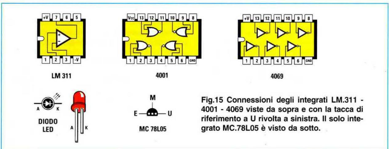
**Fig.15 Connessioni degli integrati LM.311 - 4001 - 4069 viste da sopra e con la tacca di riferimento a U rivolta a sinistra. Il solo integrato MC.78L05 è visto da sotto.**
