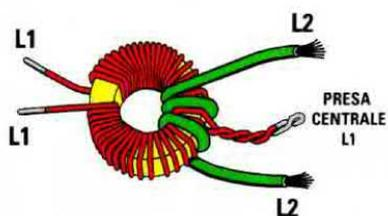
**Fig.20** Per trasmettere sulla gamma dei 3,5 MHz bisogna avvolgere 40 spire con una presa centrale per la bobina L1 usando del filo di rame smaltato da 0,3 mm e 3 spire con filo di rame isolato in plastica da 0,8-0,9 mm per la bobina L2.
