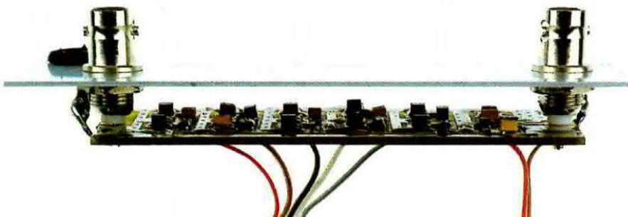
**Fig.8** Foto del circuito in SMD già fissato sul pannello posteriore.
