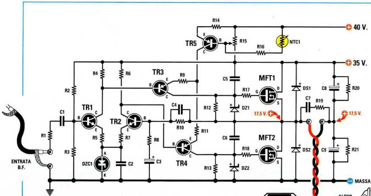
Fig.1 Schema elettrico dell'amplificatore in classe A che utilizza per lo stadio finale due mosfet di potenza. Sulla destra le connessioni dei mosfet e dei due transistor NPN e PNP viste da sotto. Tutte le resistenze sono da 1/4 di watt ad esclusione di R17-R18-R19 che sono da 1/2 watt. Le quattro resistenze siglate R2-R3-R20-R21 sono di precisione.
