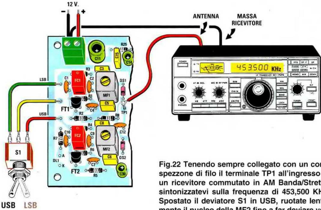
Fig.22 Tenendo sempre collegato con un corto spezzone di filo il terminale TP1 all'ingresso di un ricevitore commutato in AM Banda/Stretta, sintonizzatevi sulla frequenza di 453,500 KHz. Spostato il deviatore S1 in USB, ruotate lentamente il nucleo della MF2 fino a far deviare verso il massimo la lancetta dell'S-Meter.
