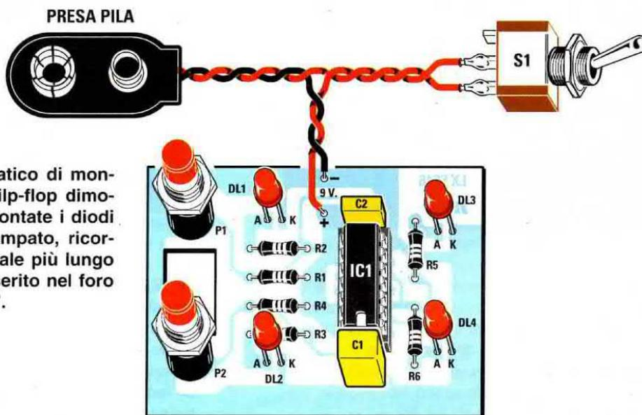
Fig.555 Schema pratico di montaggio del nostro filp-flop dimostrativo. Quando montate i diodi led sul circuito stampato, ricordatevi che il terminale più lungo (vedi fig.559) va inserito nel foro contrassegnato "A".
