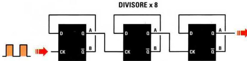
**Fig.552** Collegando in serie 3 flip-flop tipo D si ottiene un divisore x8. Quindi se sull'ingresso CK del primo divisore di sinistra viene applicata una frequenza di 100 KHz, dall'uscita QA del terzo divisore si preleveranno 12,5 KHz.
