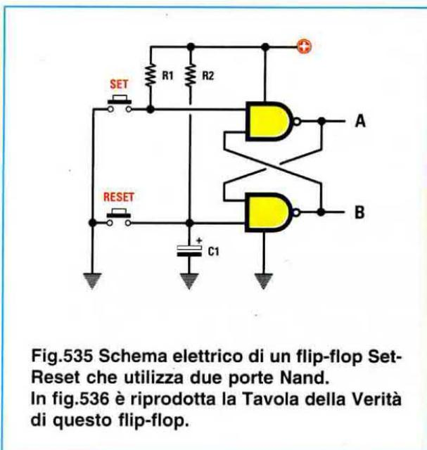
Fig.535 Schema elettrico di un flip-flop Set-Reset che utilizza due porte Nand. In fig.536 è riprodotta la Tavola della Verità di questo flip-flop.
