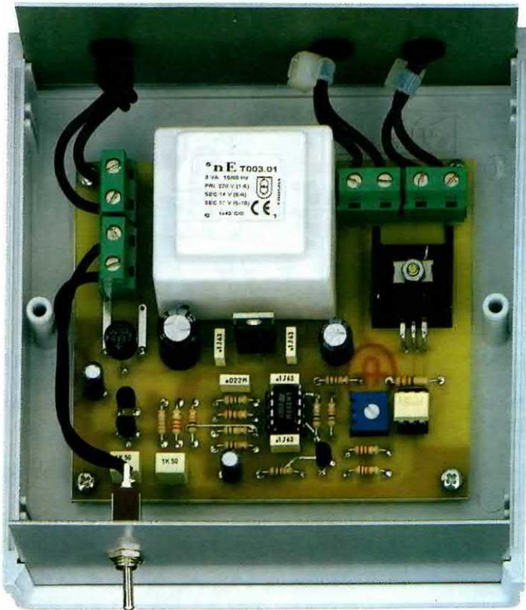
Fig.7 Sul pannello anteriore dovete praticare un foro con una punta da 7 mm per l'interruttore S1 e sul pannello posteriore 3 fori per inserire i gommini passafilo per l'ingresso del filo dei 220 volt (foro di sinistra) e quelli che vi serviranno per alimentare le lampade collegate alla morsettiere d'uscita.
