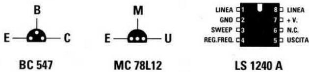
Fig.5 Connessioni del transistor BC.547 e dell'integrato stabilizzatore MC.78L12 viste da sotto e connessioni degli integrati LS.1240/A - LM.311 e del fotocoppiatore 4N35 viste da sopra.
