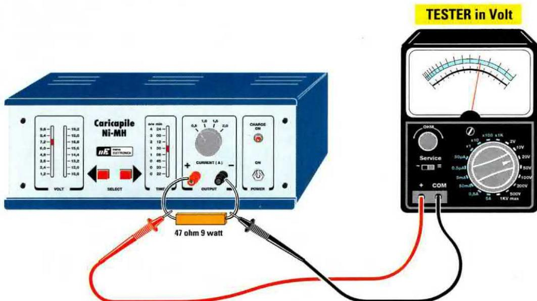
Fig.22 Poichè il caricapile fornisce in uscita una corrente costante, se sui suoi morsetti d'uscita non applicherete nessun carico, ai suoi capi leggerete sempre una tensione fissa di circa 20 volt. Per stabilire se la tensione d'uscita varia al variare del carico, dovrete applicare sui morsetti una resistenza a filo da 47 ohm 9 watt. Ruotando il commutatore S1 su 0,5 amper, ai capi della resistenza da 47 ohm leggerete, in corrispondenza di ogni portata, le tensioni indicate nella Tabella N.5.
