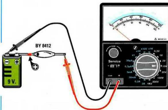
**Fig.16** Se il terminale POSITIVO del diodo risulta rivolto verso il positivo della Pila, sul Tester NON leggerete nessuna tensione. Per leggerla dovete solo capovolgere il diodo come visibile in fig.15.
