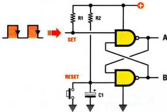
**Fig.540** Per cambiare i Livelli Logici sul terminale d'ingresso Set di un flip-flop che utilizza due porte Nand, è possibile sostituire il pulsante Set con degli impulsi prelevati dall'uscita di un qualsiasi integrato digitale.
