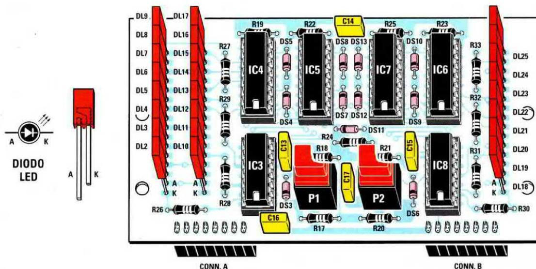
**Fig.16** Schema pratico di montaggio del circuito di visualizzazione LX.1479/B. Quando inserite nel circuito stampato i diodi led, ricordatevi che il terminale "più corto" K va sempre rivolto verso il basso. Vi ricordiamo che il pulsante P1 permette di variare la tensione di carica della pila, mentre il pulsante P2 permette di variare il tempo di carica.
