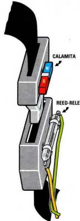
Fig.3 Come potete vedere illustrato in questo disegno, il reed relè ed il magnete vanno fissati con qualche goccia di cementatutto a presa rapida sulle custodie presenti alle due estremità della cintura di sicurezza. Prima di incollare questi due elementi, vi consigliamo di controllare se, innestando le due fibbie della cintura, il magnete si può avvicinare al reed relè fino a farlo eccitare.
