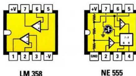
Fig.17 Connessioni G-D-S del mosfet e dei terminali E-B-C del BC.328 viste da sotto. Le connessioni degli integrati LM.358 e NE.555 sono viste da sopra, con la loro tacca di riferimento a U rivolta a sinistra.
