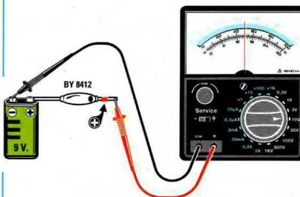
**Fig.15** Se il terminale POSITIVO del diodo risulta rivolto verso il positivo del Tester, leggerete una tensione di circa 5 volt, perchè questi diodi per alta tensione introducono una caduta di 4 volt.
