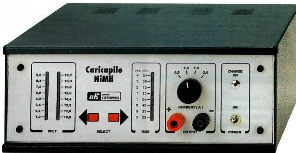
Fig.2 Ecco come si presenta il mobile e il pannello frontale di questo caricapila. Premendo il pulsante di sinistra (vedi scritta Select) variano i Volt d'uscita, mentre premendo il pulsante di destra, varia il Tempo di carica. Per variare la Corrente di carica bisogna utilizzare il commutatore rotativo presente sopra alle morsettiere d'uscita.
