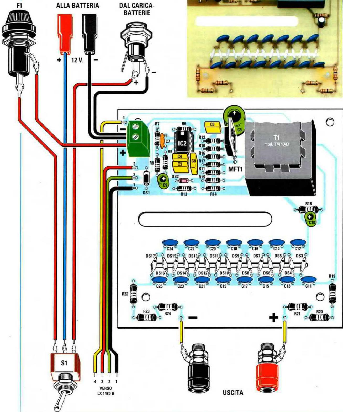
Fig.7 Schema pratico di montaggio dello stadio siglato LX.1480/B. Prima di inserire nel circuito le due barre dei 5 diodi led (vedi da DL3 a DL12), leggete le didascalie riportate nelle figg.12-13. I quattro fili presenti a sinistra vanno collegati al circuito stampato riportato in fig.6.
