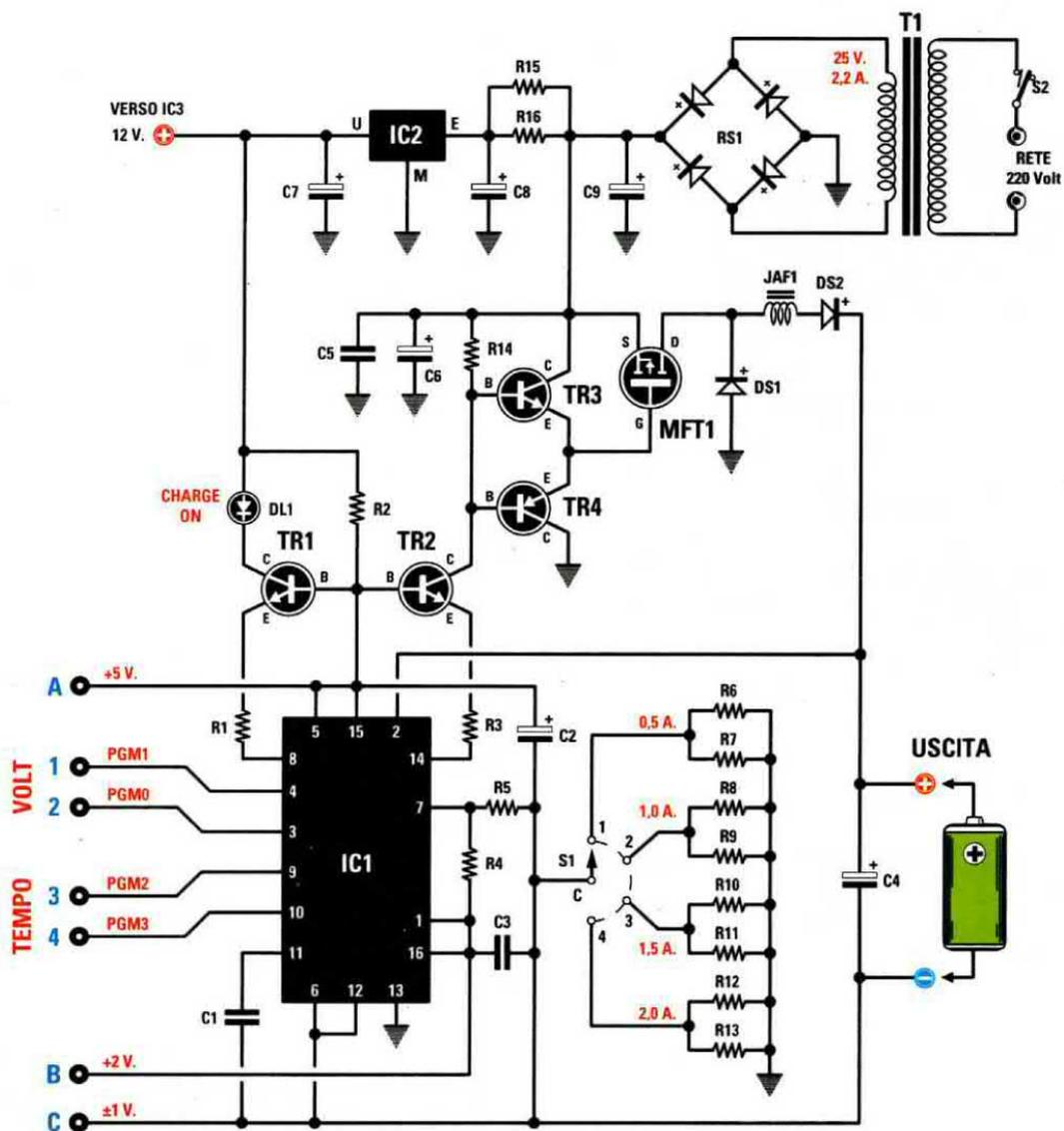
Fig.3 Schema elettrico dello stadio base siglato LX.1479. I sette terminali riportati sulla sinistra contrassegnati A-PGM1-PGM0-PGM2-PGM3-B-C vanno collegati al circuito di commutazione automatica riportato in fig.7.
