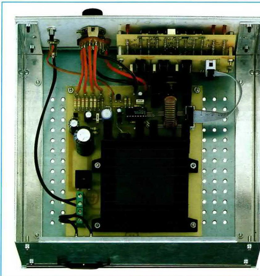
**Fig.17** Il circuito base va fissato sul piano del mobile per mezzo di distanziatori metallici ed il circuito di visualizzazione va fissato sul pannello frontale sempre per mezzo di distanziatori metallici (vedi figg.18-19).
