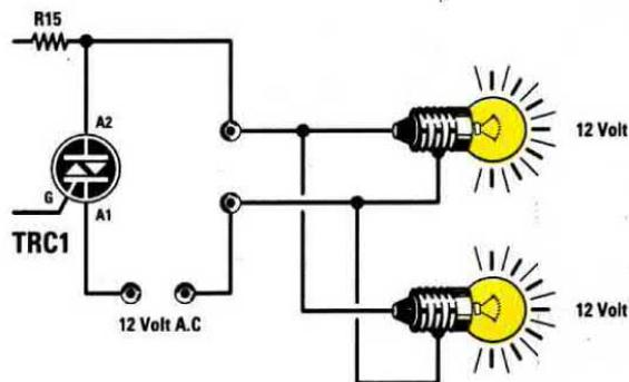
**Fig.5** Se alla morsettiera d'uscita collegate in serie due lampade da 12 V 3 Watt, per alimentare dovete utilizzare un trasformatore in grado di erogare una tensione di 24 Volt 0,13 Amper.
