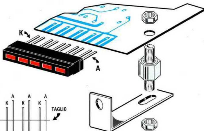
**Fig.13** Quando accorciate i terminali dei diodi led, ricordatevi che tutti gli Anodi vanno posizionati a destra.
