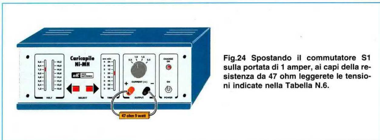
Fig.24 Spostando il commutatore S1 sulla portata di 1 amper, ai capi della resistenza da 47 ohm leggerete le tensioni indicate nella Tabella N.6.
