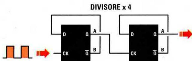
Fig.551 Collegando in serie due flip-flop tipo D si ottiene un divisore x4. Quindi applicando sull'ingresso CK una frequenza di 100 KHz, dall'uscita QA del secondo divisore si preleveranno 25 KHz.
