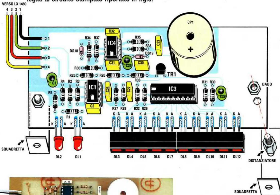
Fig.8 Foto del circuito LX.1480/B come si presenta a montaggio ultimato. Nota: il terminale + della cicalina va rivolto verso IC3.
