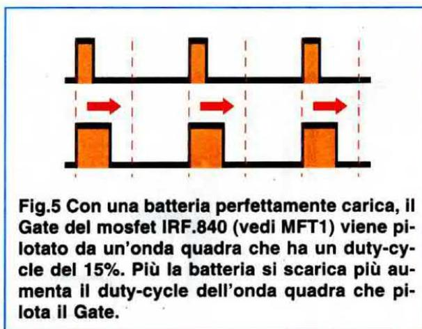
**Fig.5** Con una batteria perfettamente carica, il **Gate** del mosfet **IRF.840** (vedi **MFT1**) viene pilotato da un'onda quadra che ha un **duty-cycle** del **15%**. Più la batteria si scarica più aumenta il **duty-cycle** dell'onda quadra che pilota il **Gate**.
