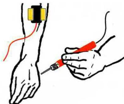
**Fig.21** La piastra in gomma collegata alla boccola Positiva può essere fissata con nastro adesivo anche ad un braccio. Se avvicinerete il puntale Negativo alla pelle fino a far accendere il 5° diodo led, potrebbe scoccare una fastidiosa scintilla.
