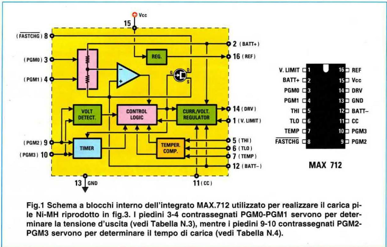
Fig.1 Schema a blocchi interno dell'integrato MAX.712 utilizzato per realizzare il carica pile Ni-MH riprodotto in fig.3. I piedini 3-4 contrassegnati PGM0-PGM1 servono per determinare la tensione d'uscita (vedi Tabella N.3), mentre i piedini 9-10 contrassegnati PGM2-PGM3 servono per determinare il tempo di carica (vedi Tabella N.4).
