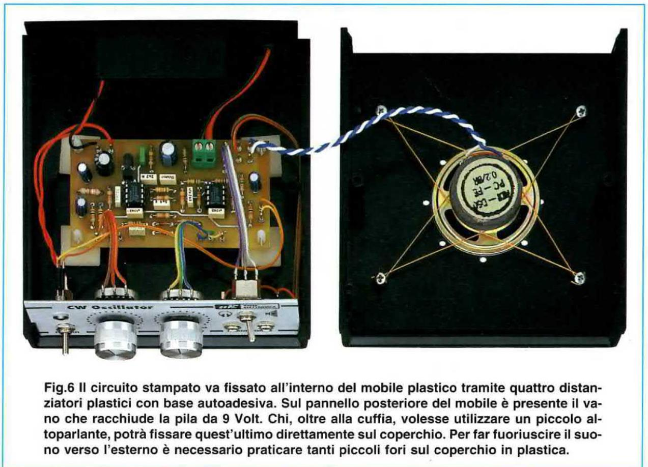
Fig.6 Il circuito stampato va fissato all'interno del mobile plastico tramite quattro distanziatori plastici con base autoadesiva. Sul pannello posteriore del mobile è presente il vano che racchiude la pila da 9 Volt. Chi, oltre alla cuffia, volesse utilizzare un piccolo altoparlante, potrà fissare quest'ultimo direttamente sul coperchio. Per far fuoriuscire il suono verso l'esterno è necessario praticare tanti piccoli fori sul coperchio in plastica.
