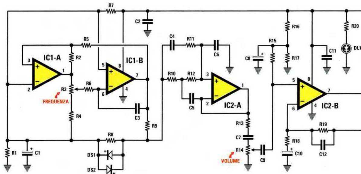
Fig.2 Schema elettrico dell'oscillografo per imparare l'alfabeto Morse. Il circuito, che utilizza due integrati e due transistor, va alimentato con una comune pila da 9 Volt.
