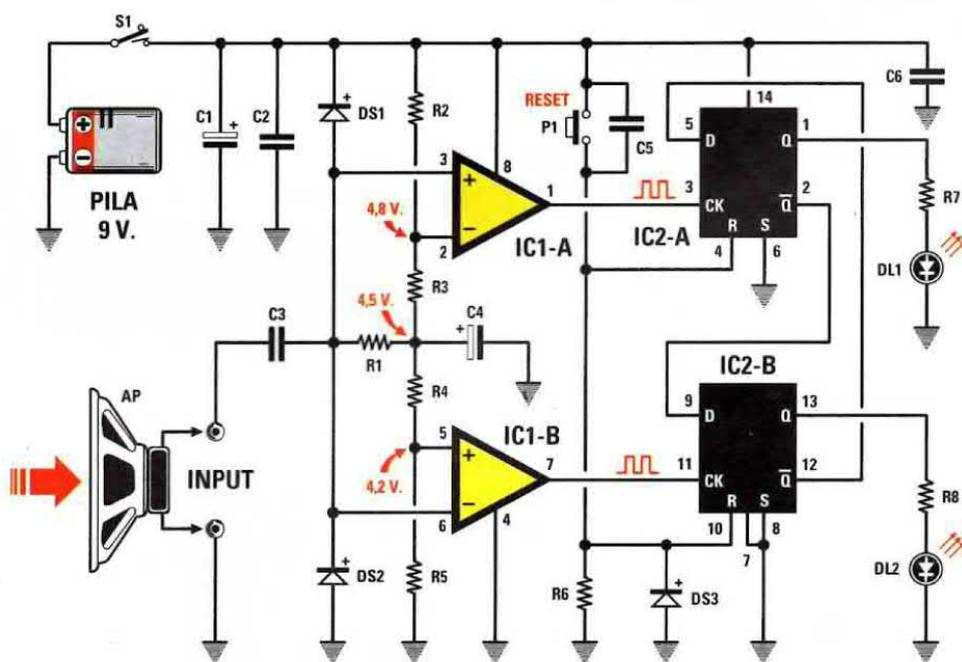
Fig.1 Schema elettrico del circuito indicatore di polarità per Altoparlanti. Il segnale che fuoriesce dall'altoparlante viene squadrato dagli operazionali IC1/A-IC1/B, utilizzati come comparatori a finestra, e poi applicato sui due flip-flop IC2/A-IC2/B utilizzati come indicatori di priorità. Le resistenze utilizzate in questo circuito sono tutte da 1/4 di watt.
