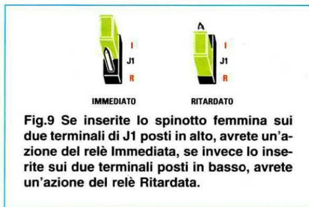
**Fig.9** Se inserite lo spinotto femmina sui due terminali di J1 posti in alto, avrete un'azione del relè **Immediata**, se invece lo inserite sui due terminali posti in basso, avrete un'azione del relè **Ritardata**.
