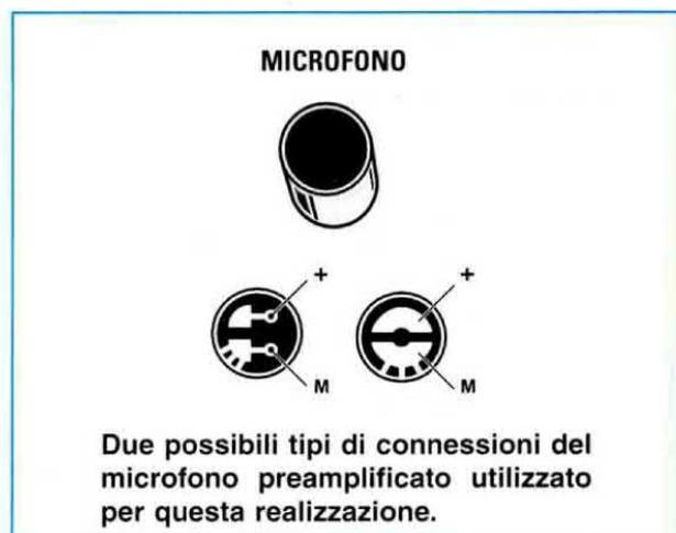
Due possibili tipi di connessioni del microfono preamplificato utilizzato per questa realizzazione.
