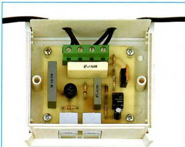
**Fig.1** Foto del circuito racchiuso dentro il suo contenitore plastico. Alla morsetteria a 4 poli collegherete la lampada e la tensione per alimentarla (vedi fig.4).
