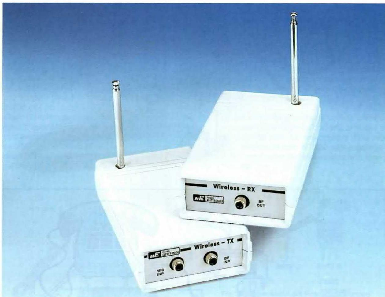
Un microtrasmettitore in FM sintonizzabile da 170 a 173 MHz in grado di erogare in antenna una potenza di circa 100 milliwatt. Il segnale erogato può essere captato con un ricevitore per Radioamatori o con uno Scanner oppure con il ricevitore FM che pubblichiamo in questo numero.
