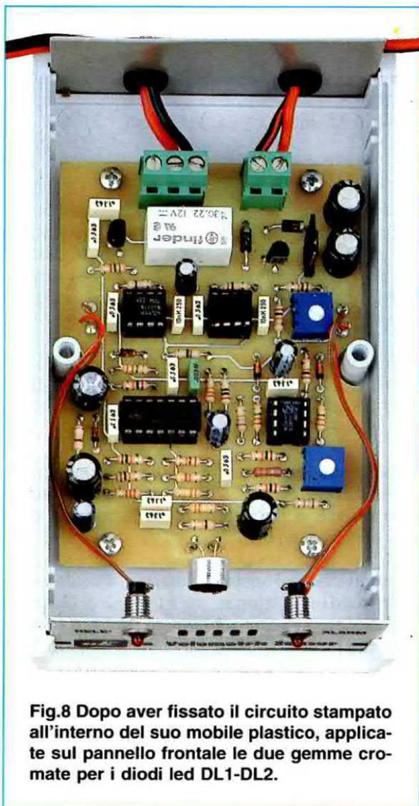
**Fig.8** Dopo aver fissato il circuito stampato all'interno del suo mobile plastico, applicate sul pannello frontale le due gemme cromate per i diodi led DL1-DL2.
