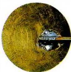
**Fig.4** Sull'estremità di questo filo va fissato un peso (vedi morsetti) che servirà per trasmettere le vibrazioni al dischetto piezoelettrico.
