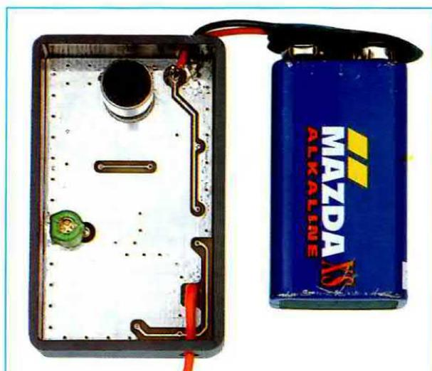
**Fig.5** Dopo aver inserito il trasmettitore nel suo mobile, dovrete fare un foro sul coperchio in corrispondenza del microfono. Molti investigatori non applicano questo coperchio, perché il microfono riesce a captare con più facilità i segnali deboli.
