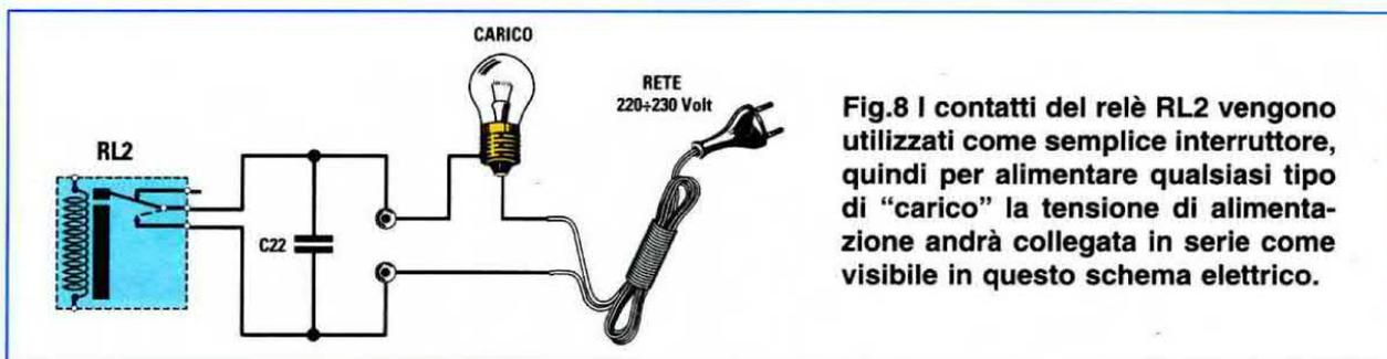
**Fig.8** I contatti del relè RL2 vengono utilizzati come semplice interruttore, quindi per alimentare qualsiasi tipo di "carico" la tensione di alimentazione andrà collegata in serie come visibile in questo schema elettrico.
