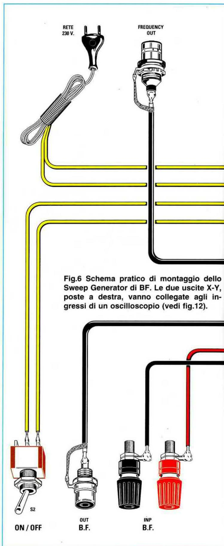
Fig.6 Schema pratico di montaggio dello Sweep Generator di BF. Le due uscite X-Y, poste a destra, vanno collegate agli ingressi di un oscilloscopio (vedi fig.12).
