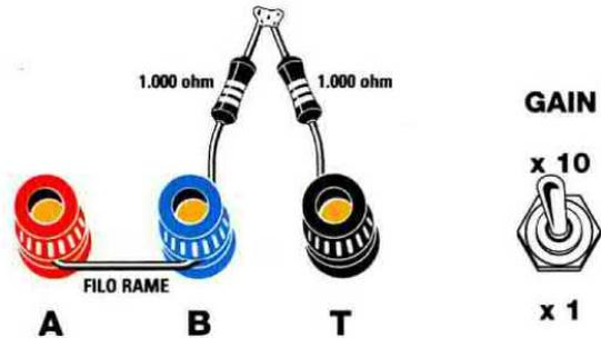
S2 e sostituite le due resistenze da **100 ohm** collegate alle due morsettiere **A-B** e **T** con due resistenze da **1.000 ohm** ponendole in **serie**, in modo da ottenere una resistenza **totale** di **2.000 ohm** (vedi fig.12).
