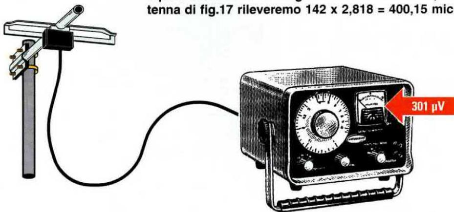
Se collegando un **Misuratore di Campo** ai capi di quest'antenna **direttiva** (vedi fig.17) rileveremo un segnale di **850 microvolt**, è intuitivo che collegando questo strumento ai capi di un **normale dipolo** (vedi fig.18) noi rileveremo un segnale di soli:
