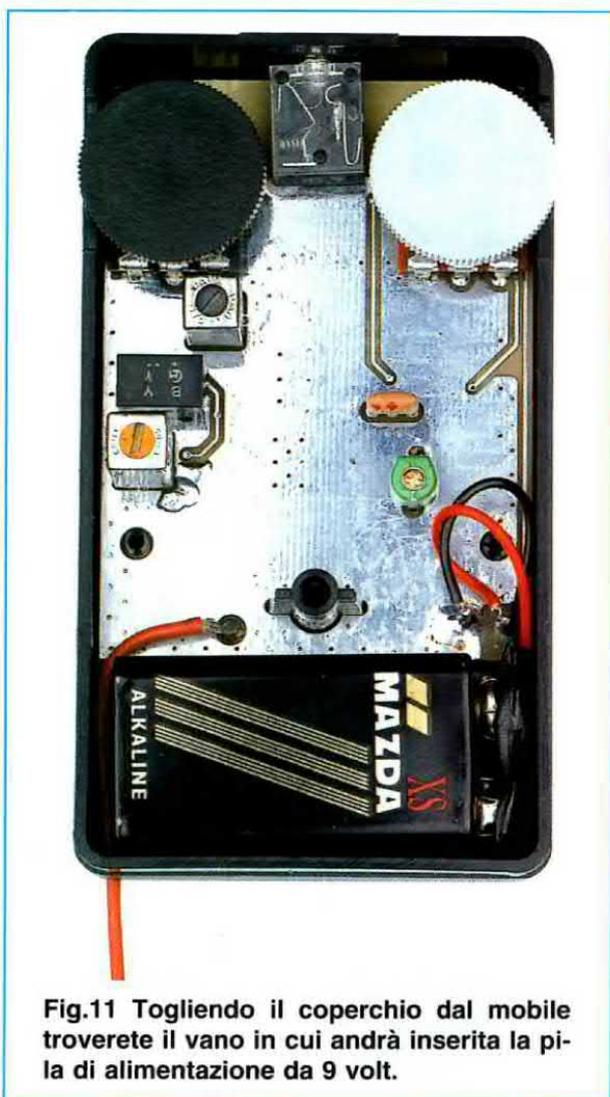
**Fig.11** Togliendo il coperchio dal mobile troverete il vano in cui andrà inserita la pila di alimentazione da 9 volt.
