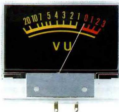
Fig.27 Quando la lancetta di un Vu-Meter raggiunge i 0 dB, otterremo in uscita la max potenza erogabile dall'amplificatore.
