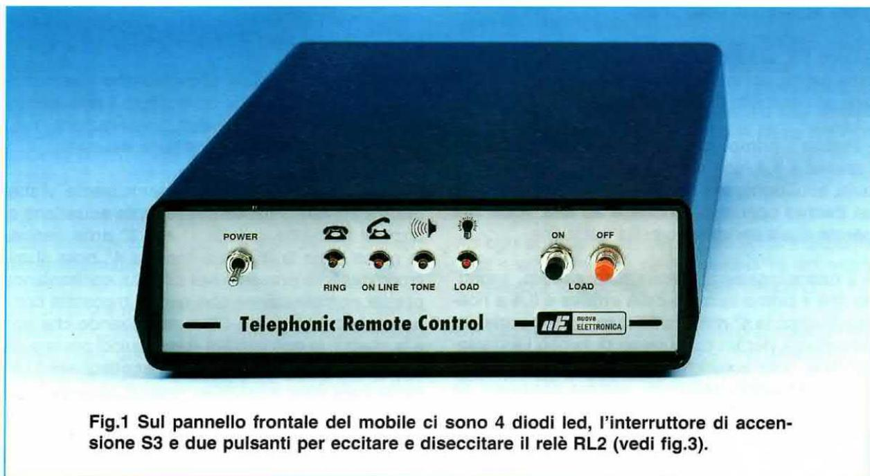
Fig.1 Sul pannello frontale del mobile ci sono 4 diodi led, l'interruttore di accensione S3 e due pulsanti per eccitare e diseccitare il relè RL2 (vedi fig.3).
