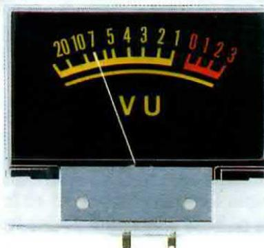
Fig.28 Se la lancetta dovesse raggiungere solo i 7 dB, otterremo in uscita una potenza 5 volte inferiore al valore max.
