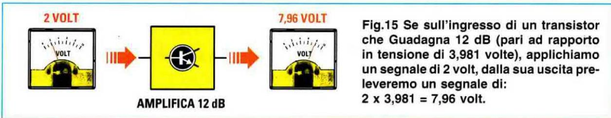
Fig.15 Se sull'ingresso di un transistor che Guadagna 12 dB (pari ad rapporto in tensione di 3,981 volte), applichiamo un segnale di 2 volt, dalla sua uscita preleveremo un segnale di:
