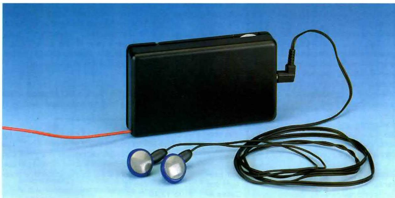
**Fig.2** Il mobile del ricevitore ha, invece, queste dimensioni: Lunghezza 180 mm, Larghezza 60 mm, Spessore 24 mm. Come si vede in fig.11, in questo mobile è presente un vano per la pila di alimentazione da 9 volt. Nella presa uscita BF del ricevitore (vedi fig.7) potrete inserire un auricolare o una comune cuffia.
