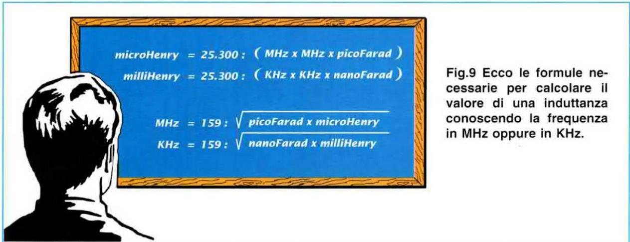
Fig.9 Ecco le formule necessarie per calcolare il valore di una induttanza conoscendo la frequenza in MHz oppure in KHz.
