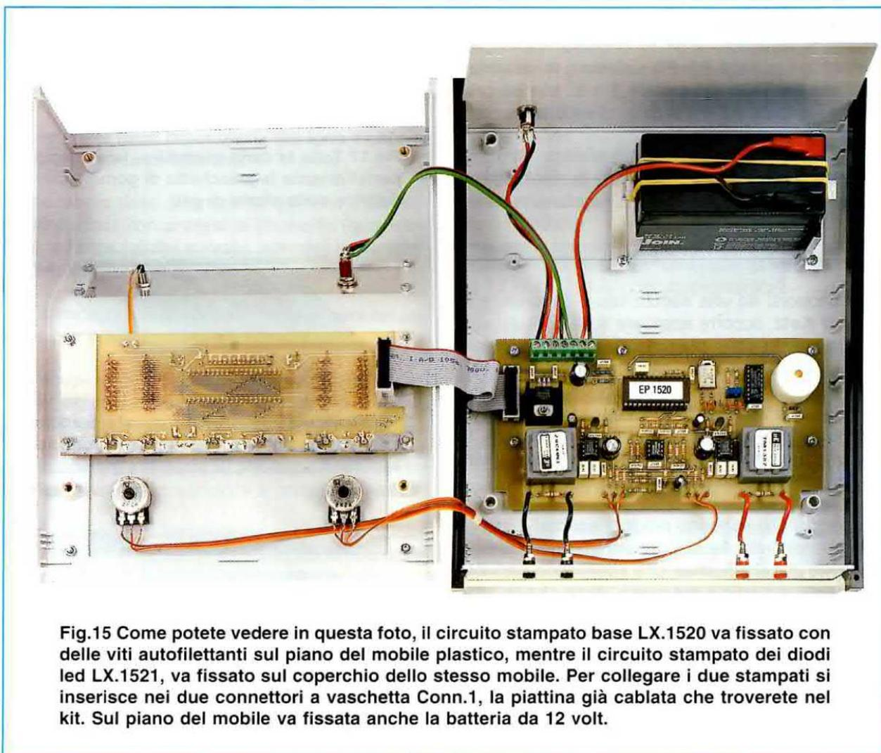
Fig.15 Come potete vedere in questa foto, il circuito stampato base LX.1520 va fissato con delle viti autofilettanti sul piano del mobile plastico, mentre il circuito stampato dei diodi led LX.1521, va fissato sul coperchio dello stesso mobile. Per collegare i due stampati si inserisce nei due connettori a vaschetta Conn.1, la piattina già cablata che troverete nel kit. Sul piano del mobile va fissata anche la batteria da 12 volt.
