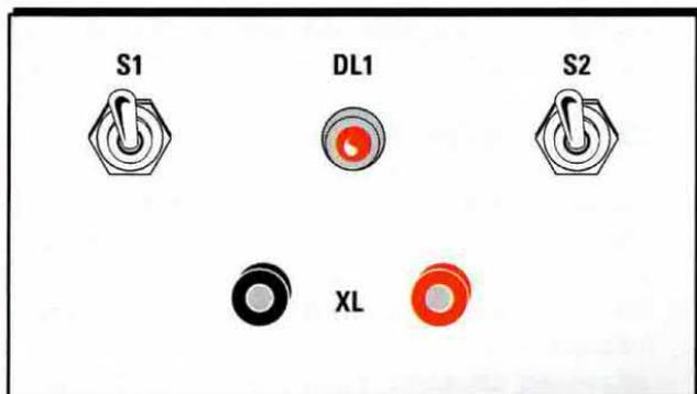
Fig.7 Sul pannello anteriore fissate, alle estremità, i due deviatori S1-S2, al centro la gemma cromata per il diodo led e sotto le due boccole XL per inserire le induttanze da testare.
