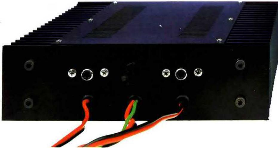
Fig.14 Sul pannello posteriore del mobile metallico fissate le due prese d'ingresso per il segnale BF e il portafusibile (vedi fig.6). Sempre da questo pannello farete uscire i fili che andranno a collegarsi agli Altoparlanti o alle Casse Acustiche e anche quelli per collegarsi ai 12 volt della batteria. Nei fori di passaggio inserite i gommini passafilo.
