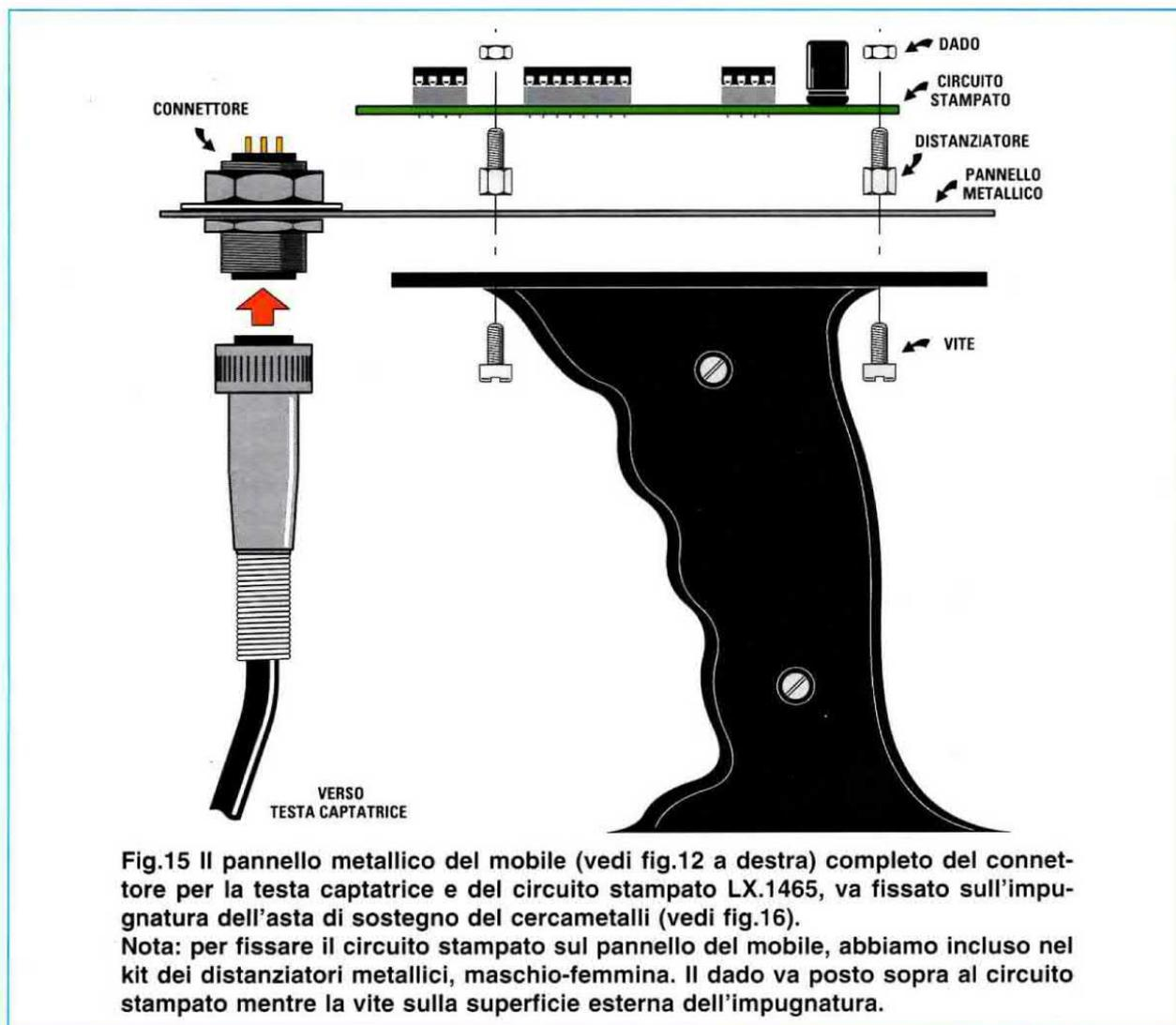
**Fig.15** Il pannello metallico del mobile (vedi fig.12 a destra) completo del connettore per la testa captatrice e del circuito stampato LX.1465, va fissato sull'impugnatura dell'asta di sostegno del cercametalli (vedi fig.16).
