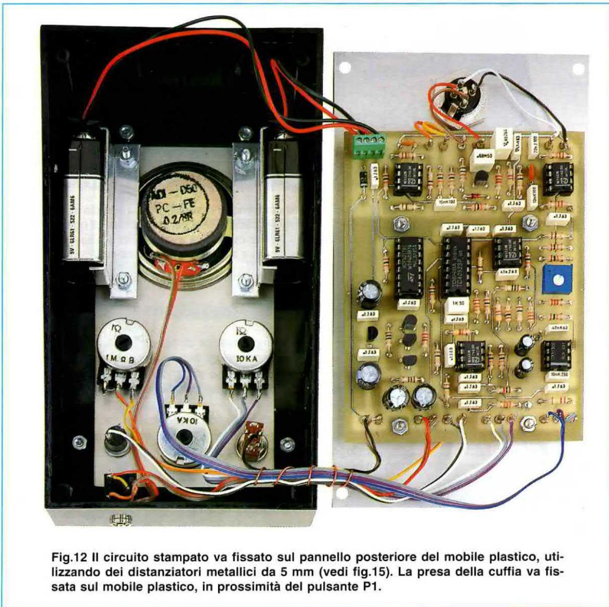
Fig.12 Il circuito stampato va fissato sul pannello posteriore del mobile plastico, utilizzando dei distanziatori metallici da 5 mm (vedi fig.15). La presa della cuffia va fissata sul mobile plastico, in prossimità del pulsante P1.
