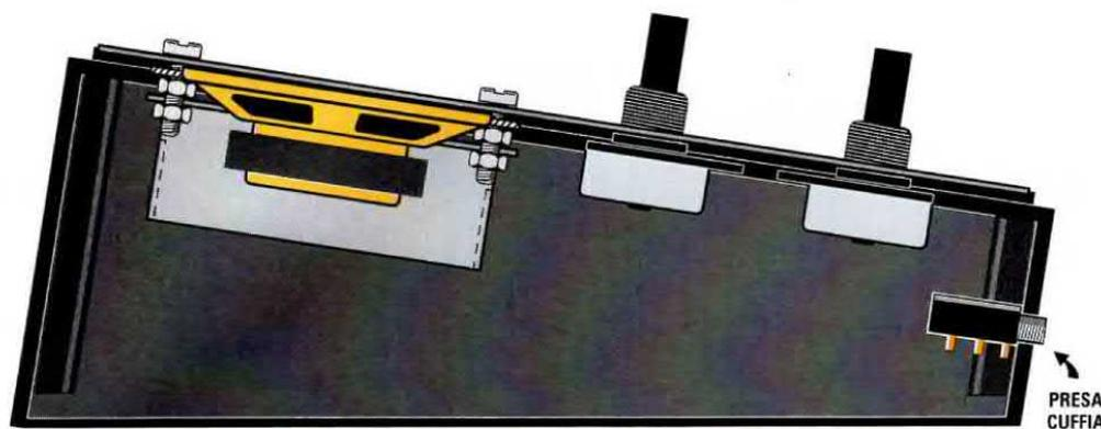
Fig.14 Il pannello frontale metallico di questo cercametalli (vedi fig.5) va fissato sul mobile plastico utilizzando quattro viti in ferro più dado. Sulla parete laterale di questo mobile visibile a destra, fissate la presa per la cuffia. La cuffia è un accessorio, pertanto potreste anche escludere questa presa qualora non vi necessiti.
