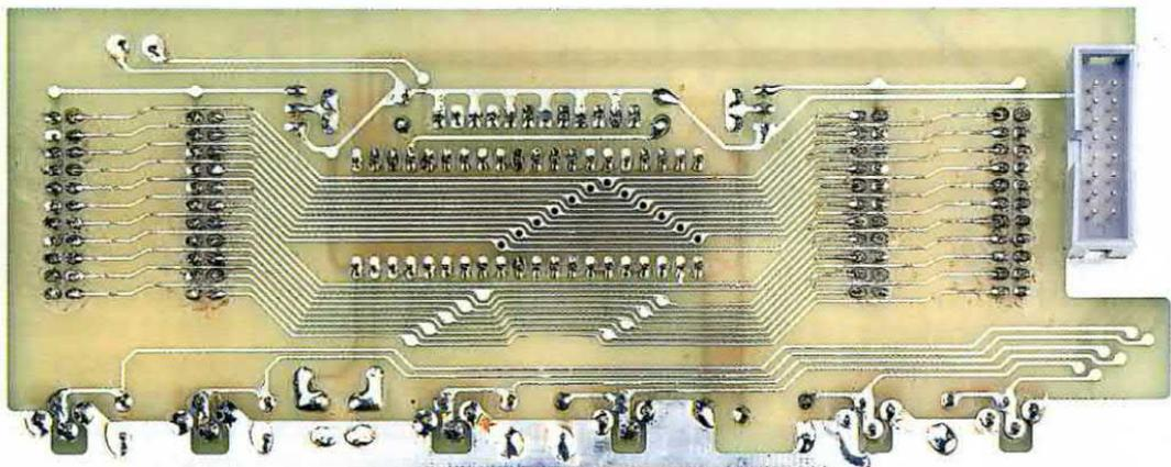
Fig.11 Foto del circuito stampato LX.1521 visto dal lato opposto. Da questo lato va inserito sulla destra il connettore a vaschetta, rivolgendo la tacca a U verso sinistra.
