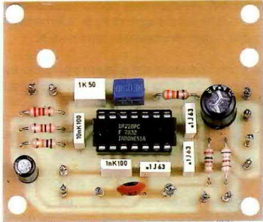
Fig.4 Ecco come si presenta il circuito stampato LX.1522 con sopra montati tutti i componenti richiesti. Vi facciamo presente che le foto dei primi esemplari sono sprovviste di disegno serigrafico che viene inserito solo nella fase di produzione.
