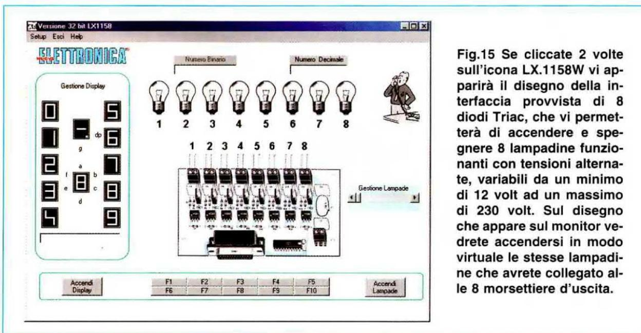
Fig.15 Se cliccate 2 volte sull'icona LX.1158W vi apparirà il disegno della interfaccia provvista di 8 diodi Triac, che vi permetterà di accendere e spegnere 8 lampadine funzionanti con tensioni alternate, variabili da un minimo di 12 volt ad un massimo di 230 volt. Sul disegno che appare sul monitor vedrete accendersi in modo virtuale le stesse lampadine che avrete collegato alle 8 morsettiere d'uscita.
