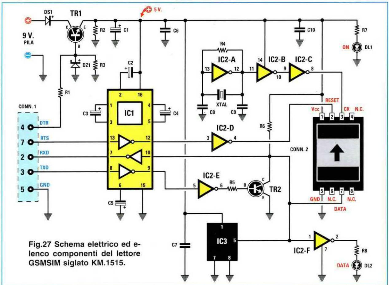
Fig.27 Schema elettrico ed elenco componenti del lettore GSM SIM siglato KM.1515.
