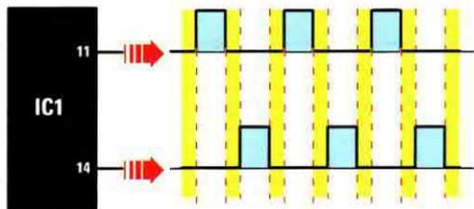
**Fig.2** Dai piedini 11-14 dell'integrato SG.3524 escono degli impulsi ad onda quadra sfasati di 180°, che vengono utilizzati per pilotare i transistor TR2-TR3-TR4-TR5 (vedi fig.3). Per mantenere stabile la tensione d'uscita del convertitore, l'integrato varia in modo automatico il duty-cycle delle onde quadre.
