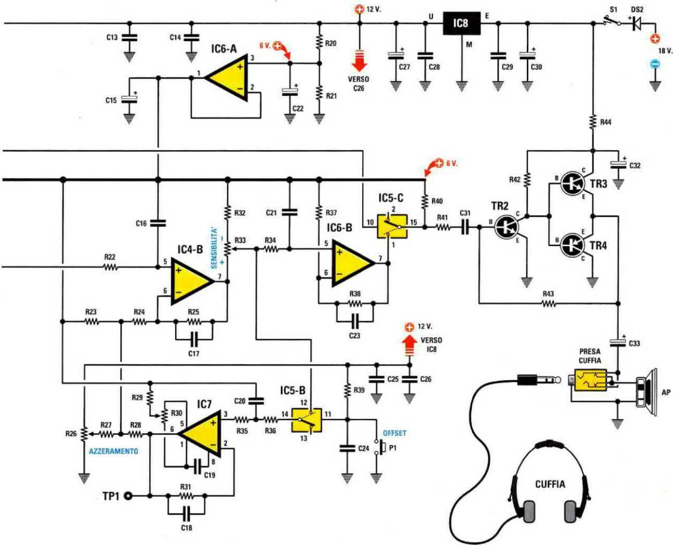
Dopo aver ruotato le manopole dei potenziometri R10-R26-R33 a metà corsa, ruotate il cursore del trimmer R30 fino a leggere su TP1 una tensione di 6 volt.
