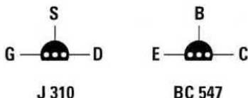
In alto, lo schema elettrico di questo preamplificatore a larga banda e, qui a sinistra, connessioni del fet J310 e del transistor BC.547 viste da sotto.
