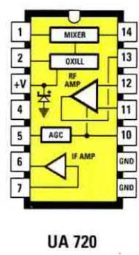
Fig.3 Connessioni dell'integrato uA.720 viste da sopra e con la tacca di riferimento ad U rivolta verso l'alto.
