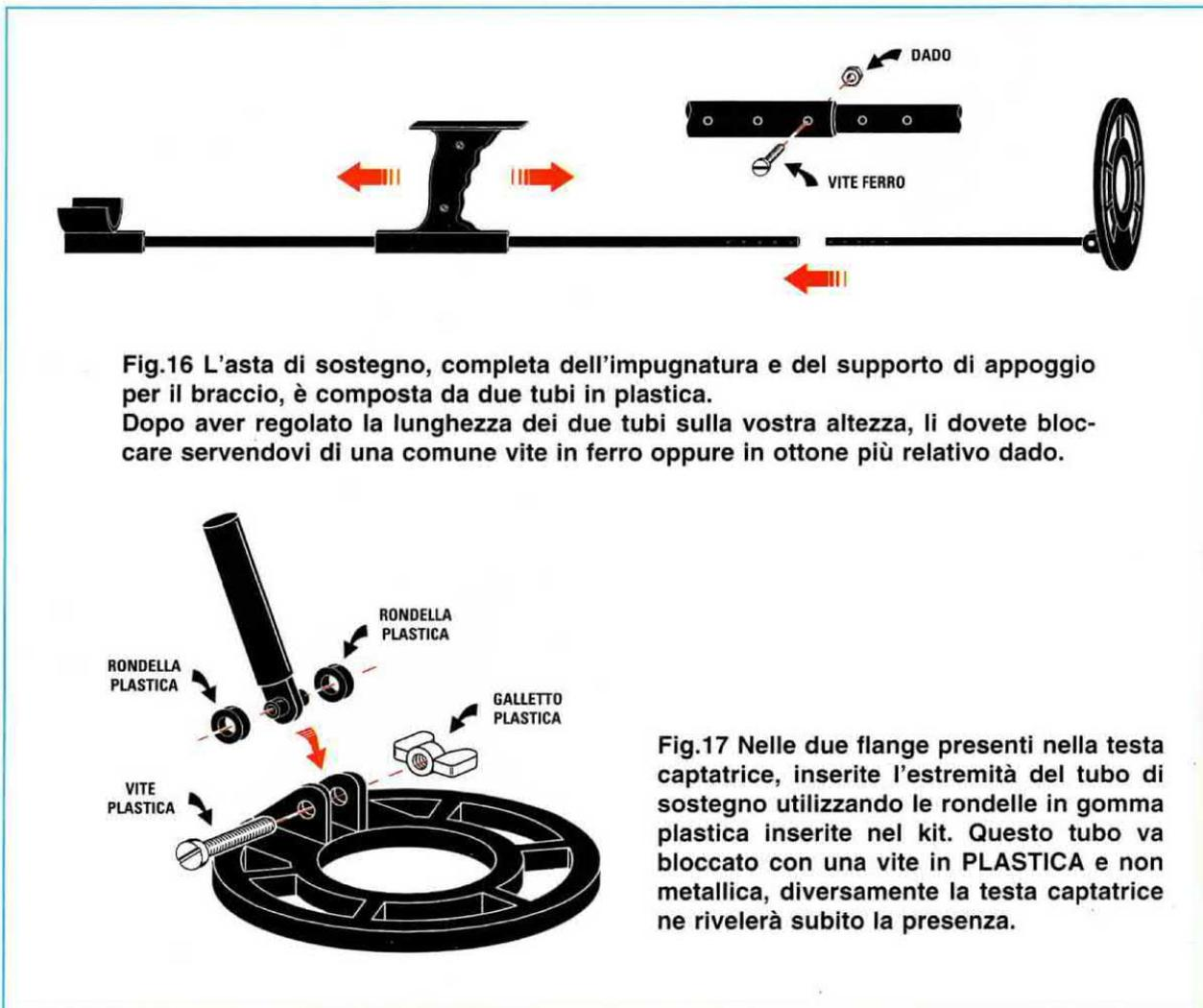
**Fig.16** L'asta di sostegno, completa dell'impugnatura e del supporto di appoggio per il braccio, è composta da due tubi in plastica. Dopo aver regolato la lunghezza dei due tubi sulla vostra altezza, li dovete bloccare servendovi di una comune vite in ferro oppure in ottone relativo dado.
