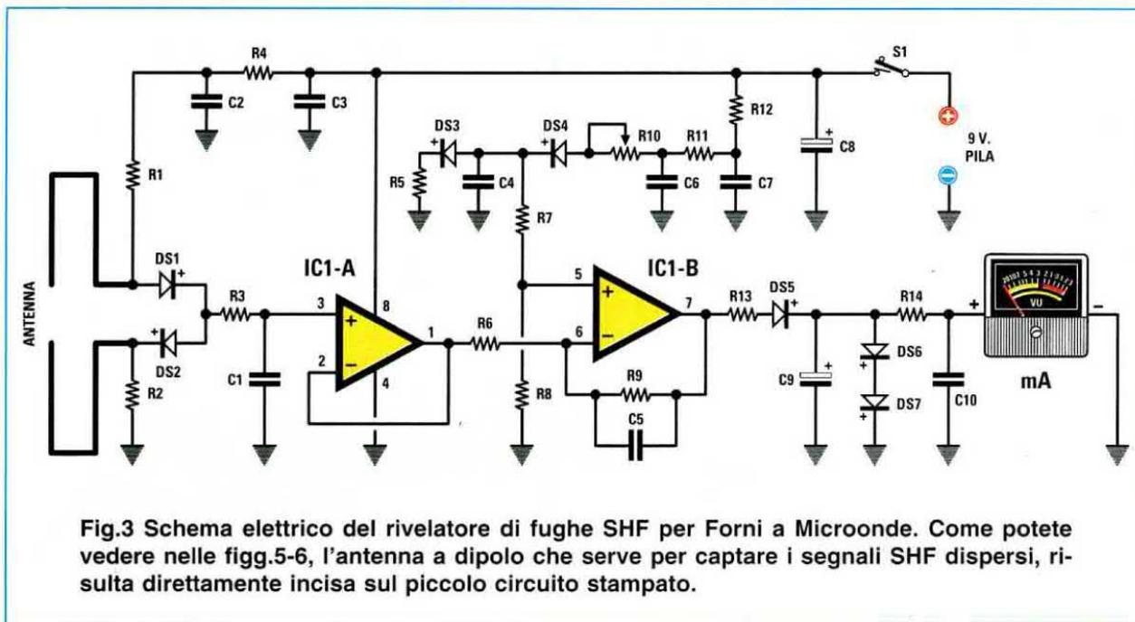
**Fig.3** Schema elettrico del rivelatore di fughe SHF per Forni a Microonde. Come potete vedere nelle figg.5-6, l'antenna a dipolo che serve per captare i segnali SHF dispersi, risulta direttamente incisa sul piccolo circuito stampato.
