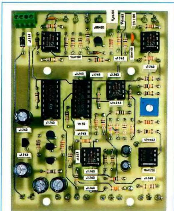
**Fig.8** In questa foto leggermente ridotta potete vedere come si presenta il circuito stampato LX.1465 con sopra già montati tutti i componenti. Il circuito stampato che vi forniremo è completo del disegno serigrafico dei componenti.
