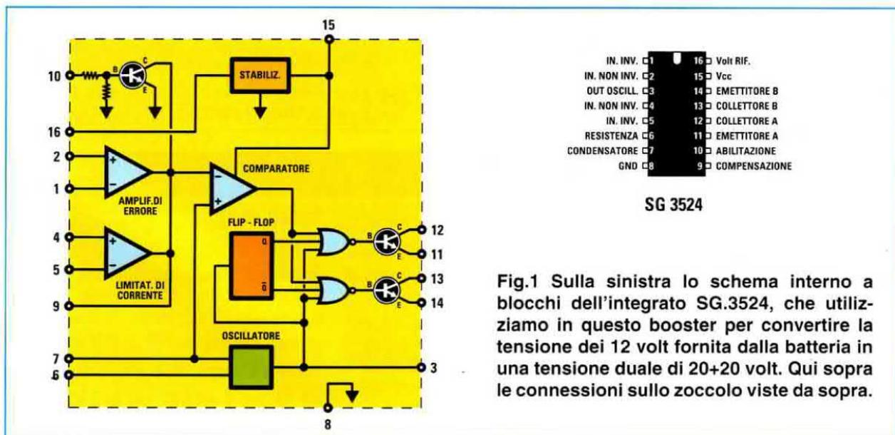
Fig.1 Sulla sinistra lo schema interno a blocchi dell'integrato SG.3524, che utilizziamo in questo booster per convertire la tensione dei 12 volt fornita dalla batteria in una tensione duale di 20+20 volt. Qui sopra le connessioni sullo zoccolo viste da sopra.
