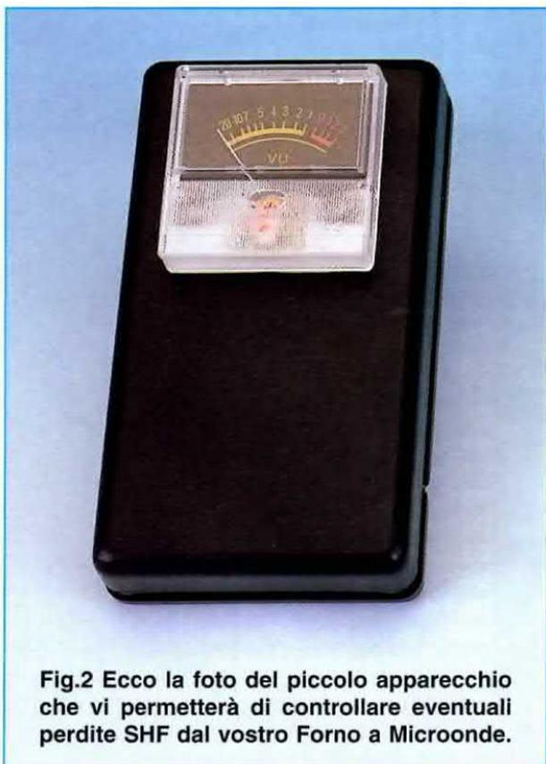
**Fig.2** Ecco la foto del piccolo apparecchio che vi permetterà di controllare eventuali perdite SHF dal vostro Forno a Microonde.
