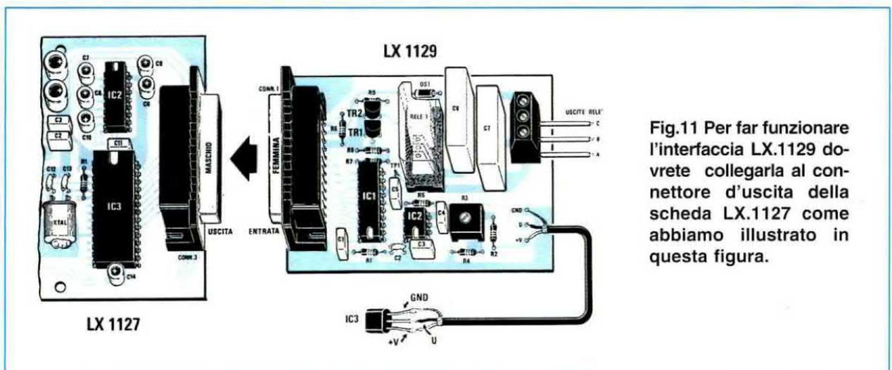
**Fig.11** Per far funzionare l'interfaccia LX.1129 dovrete collegarla al connettore d'uscita della scheda LX.1127 come abbiamo illustrato in questa figura.
