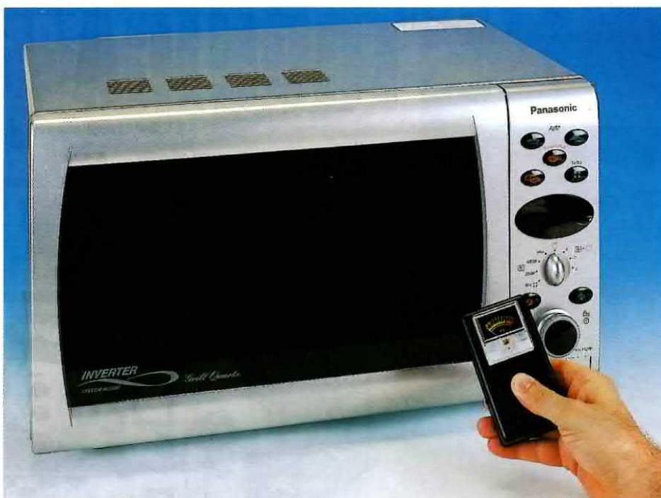
Fig.1 Per verificare se il vostro Forno a Microonde presenta delle fughe di SHF, dovete spostare lo strumento lungo il perimetro dello sportello in corrispondenza delle cerniere e della guarnizione.
