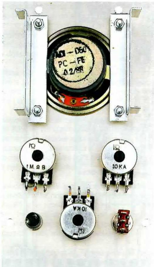
**Fig.11** Sul pannello frontale vanno fissati, oltre all'altoparlante, anche i 3 potenziometri, il pulsante P1 e il deviatore S1. Ai lati delle due squadrette di sostegno per l'altoparlante vanno collocate le pile da 9 volt come ben visibile in fig.12.
