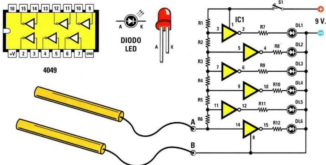
In alto, schema elettrico del circuito e connessioni dell'integrato 4049 viste dall'alto e con la tacca di riferimento rivolta verso sinistra.
