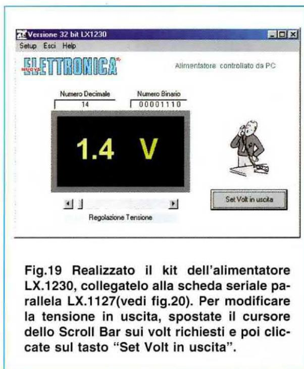
**Fig.19 Realizzato il kit dell'alimentatore LX.1230, collegatelo alla scheda seriale parallela LX.1127(vedi fig.20). Per modificare la tensione in uscita, spostate il cursore dello Scroll Bar sui volt richiesti e poi cliccate sul tasto "Set Volt in uscita".**
