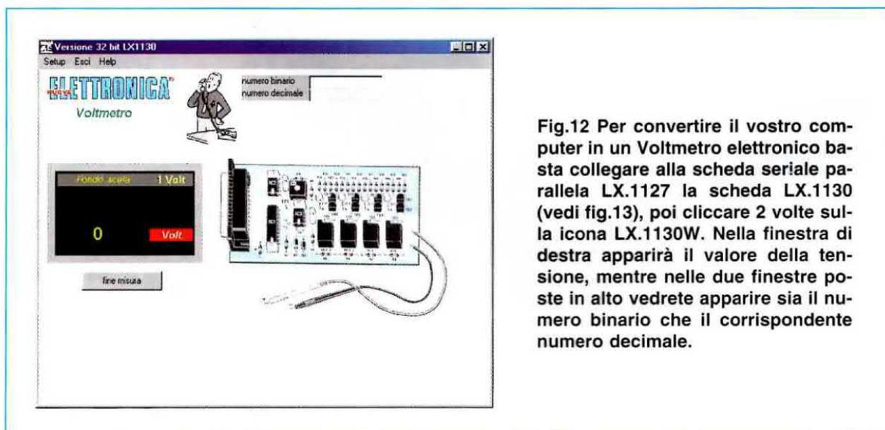
**Fig.12** Per convertire il vostro computer in un Voltmetro elettronico basta collegare alla scheda seriale parallela LX.1127 la scheda LX.1130 (vedi fig.13), poi cliccare 2 volte sulla icona LX.1130W. Nella finestra di destra apparirà il valore della tensione, mentre nelle due finestre poste in alto vedrete apparire sia il numero binario che il corrispondente numero decimale.
