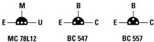
Fig.7 Connessioni viste da sopra degli integrati utilizzati in questo cercametalli tenendo la loro tacca di riferimento a U rivolta verso sinistra. Le connessioni dei transistor e dell'integrato MC.78L12 sono viste da sotto.
