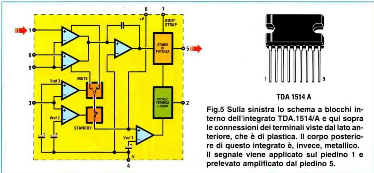
Fig.5 Sulla sinistra lo schema a blocchi interno dell'integrato TDA.1514/A e qui sopra le connessioni dei terminali viste dal lato anteriore, che è di plastica. Il corpo posteriore di questo integrato è, invece, metallico. Il segnale viene applicato sul piedino 1 e prelevato amplificato dal piedino 5.
