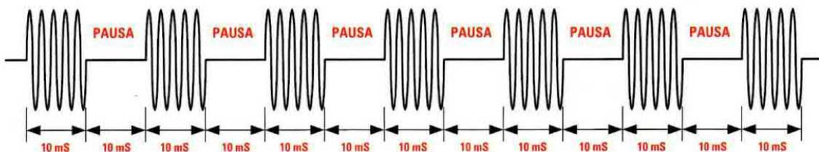
**Fig.1** L'onda di Kotz è un'onda sinusoidale con una frequenza di 2.500 hertz che, in maniera continuativa, viene tenuta attiva per un tempo di 10 millisecondi e in pausa per un tempo di 10 millisecondi (vedi disegno). Questi treni d'onda vengono utilizzati in campo terapeutico per guarire certe malattie e anche in campo sportivo per fare ginnastica passiva.
