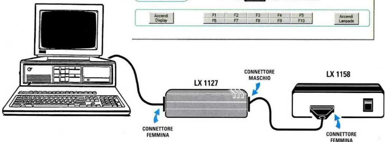
Fig.18 Come già saprete, per far funzionare la scheda LX.1158 la dovrete collegare tramite un cavo cablato alla interfaccia seriale-parallelo LX.1127, che avrete già collegato al computer. **IMPORTANTE:** se cliccate sull'icona LX.1158W senza aver collegato questa scheda alla interfaccia LX.1127, sul monitor vedrete ugualmente apparire il disegno della scheda con tutte le LAMPADE e potrete anche vedere tutti i giochi di luci che si possono ottenere con i tasti funzione da F1 a F10.
