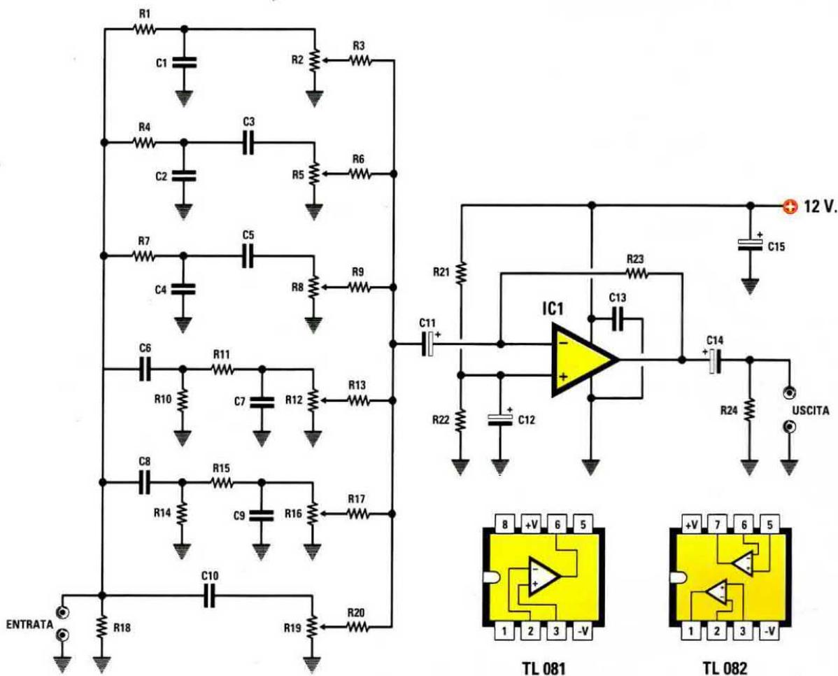
In alto, schema elettrico di questo equalizzatore e connessioni, viste da sopra, dell'integrato TL081 necessario per la realizzazione della versione mono e dell'integrato TL082 necessario per la realizzazione della versione stereo.
