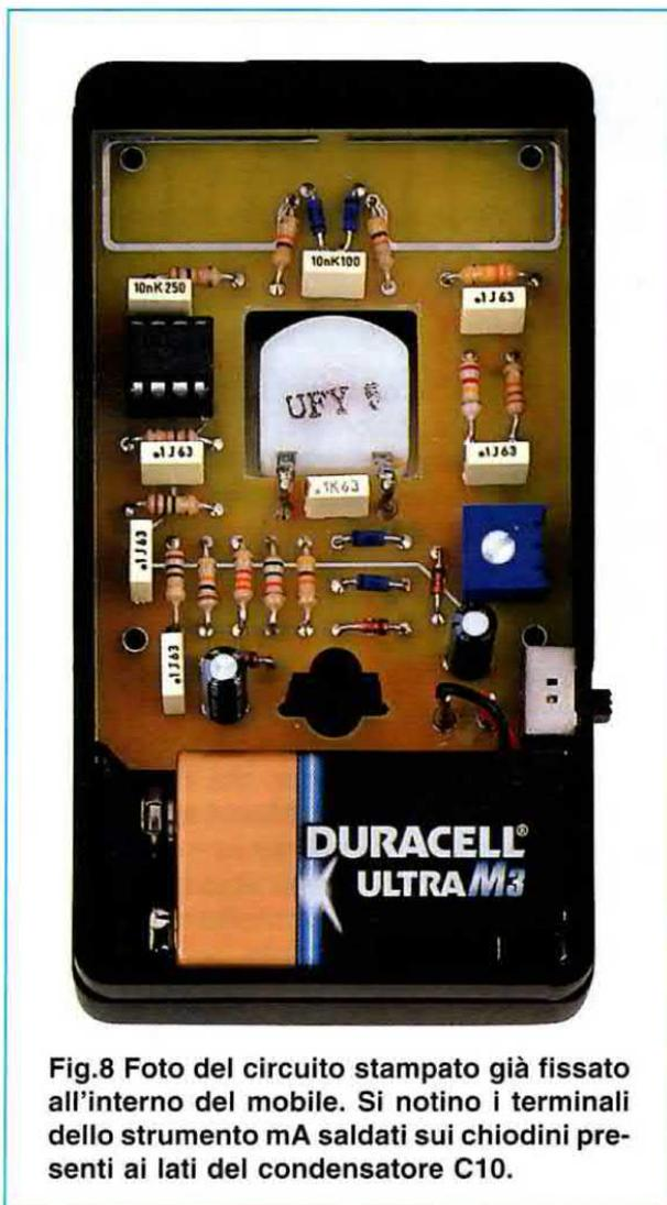
**Fig.8** Foto del circuito stampato già fissato all'interno del mobile. Si notino i terminali dello strumento mA saldati sui chiodini presenti ai lati del condensatore C10.
