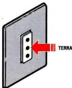
**Fig.5** Vi ricordiamo che il "foro centrale" presente in ogni presa rete da 230 volt è sempre collegato ad una presa Terra. Se vicino al ricevitore non avete nessuna presa di rete, potrete collegarvi con un filo, isolato in plastica, al mobile metallico di un qualsiasi elettrodomestico, essendo quest'ultimo sicuramente collegato a Terra.
