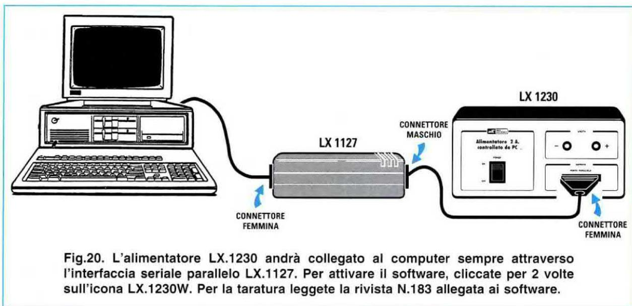
**Fig.20.** L'alimentatore LX.1230 andrà collegato al computer sempre attraverso l'interfaccia seriale parallelo LX.1127. Per attivare il software, cliccate per 2 volte sull'icona LX.1230W. Per la taratura leggete la rivista N.183 allegata ai software.
