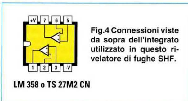
**Fig.4** Connessioni viste da sopra dell'integrato utilizzato in questo rivelatore di fughe SHF.
