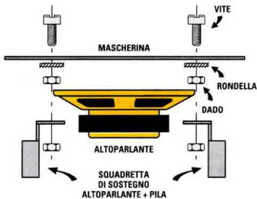
**Fig.10** Per fissare l'altoparlante sul pannello frontale del mobile usate le due squadrette inserite nel kit. Per tenere ben ferme quest'ultime, vi consigliamo di inserire 4 distanziatori, costituiti da dado+rondella, tra le squadrette e il pannello.
