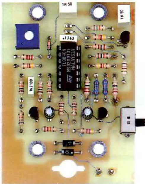
Fig.4 Qui sopra la foto del circuito stampato **LX.1518** con sopra già montati tutti i compo- nenti. Anche se in questa foto non appare, il circuito stampato che vi forniremo risulta se- grifagato con tutte le sigle dei componenti.
