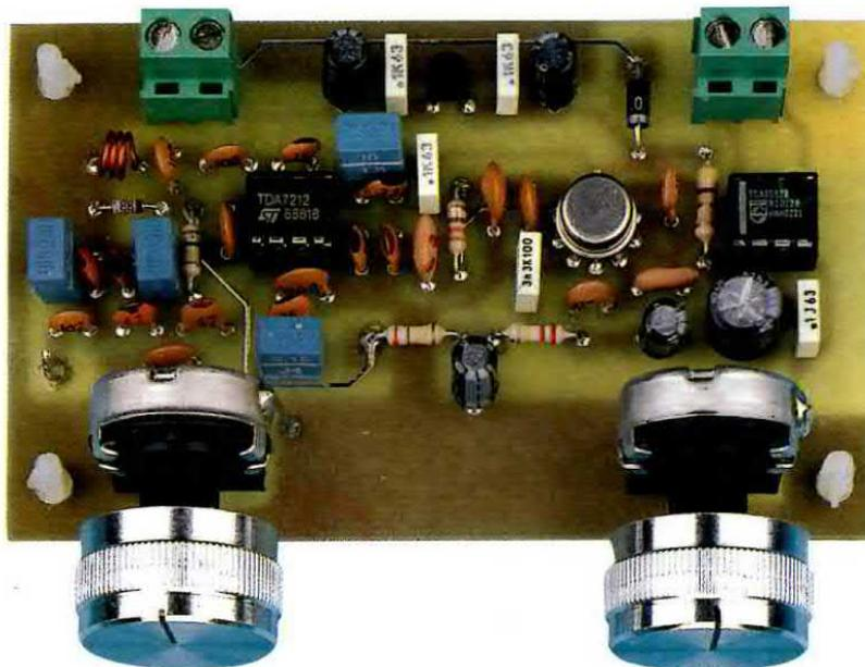
Fig.6 Foto del ricevitore come si presenta a montaggio ultimato. Per ottenere un suono molto più armonioso, consigliamo sempre di appoggiare l'altoparlante sopra una piccola tavoletta di legno oppure sopra un supporto di cartone, provvisti entrambi di un foro centrale. Se avete nella stanza delle lampade fluorescenti accese, provate a spegnerle perchè potrebbero generare del ronzio.
