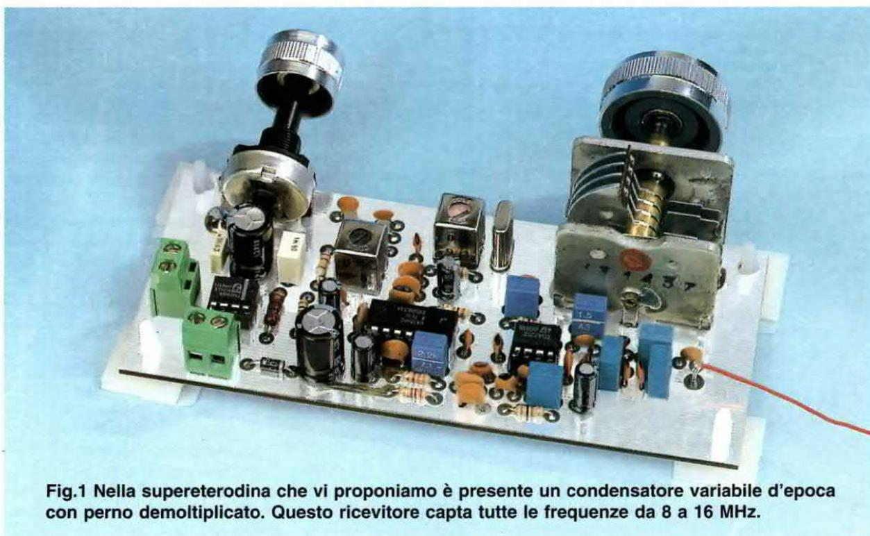
Fig.1 Nella supereterodina che vi proponiamo è presente un condensatore variabile d'epoca con perno demoltiplicato. Questo ricevitore capta tutte le frequenze da 8 a 16 MHz.
