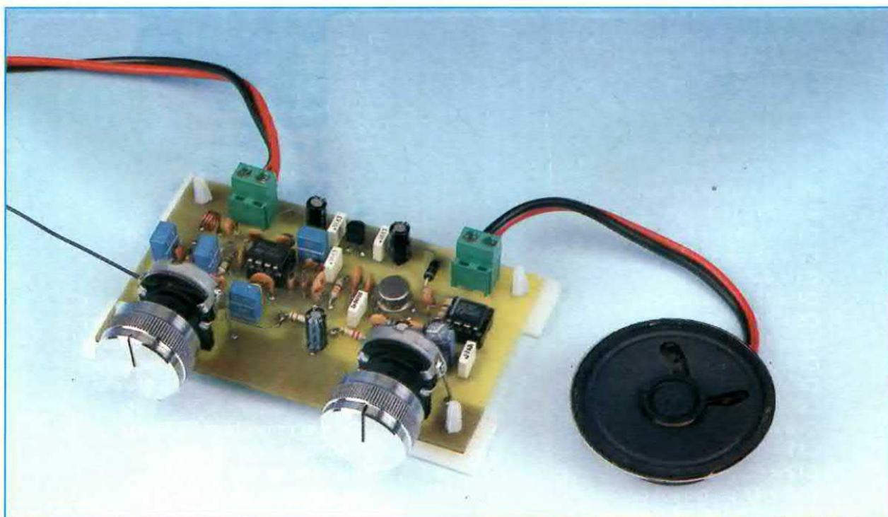
Fig.1 Foto del ricevitore come si presenta a montaggio ultimato. Per alimentare questo ricevitore occorre una tensione di **12 volt**, che potete prelevare dal kit **LX.5004** che vi abbiamo presentato nella rivista **N.186** oppure da un qualsiasi altro alimentatore stabilizzato.
