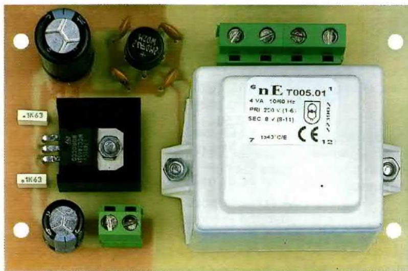
Fig.38 Ecco come si presenta a montaggio ultimato lo stadio di alimentazione in grado di erogare 5 volt. Il frequenzimetro può essere alimentato anche da una qualsiasi altra sorgente in grado di erogare 5 volt.
