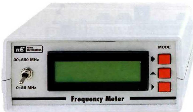
Fig.32 Foto del mobile plastico utilizzato per il frequenzimetro. Il pannello frontale, in alluminio, vi verrà fornito già forato e serigrafato.
