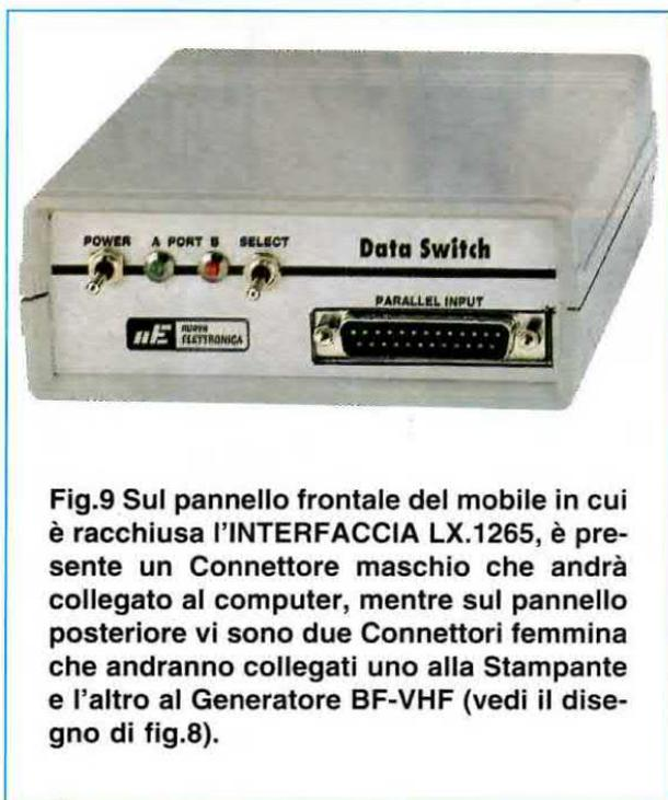
**Fig.9** Sul pannello frontale del mobile in cui è racchiusa l'INTERFACCIA LX.1265, è presente un Connettore maschio che andrà collegato al computer, mentre sul pannello posteriore vi sono due Connettori femmina che andranno collegati uno alla Stampante e l'altro al Generatore BF-VHF (vedi il disegno di fig.8).
