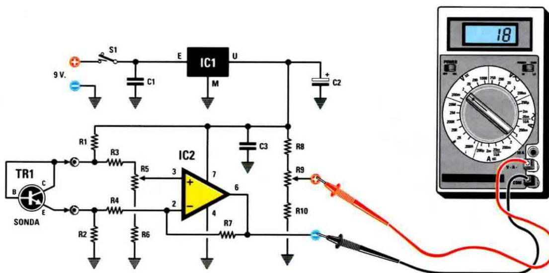
Fig.3 Schema elettrico del circuito del termometro che utilizza come sonda un integrato NPN tipo 2N.2222. Per l'alimentazione l'Autore ha utilizzato una pila da 9 volt.
