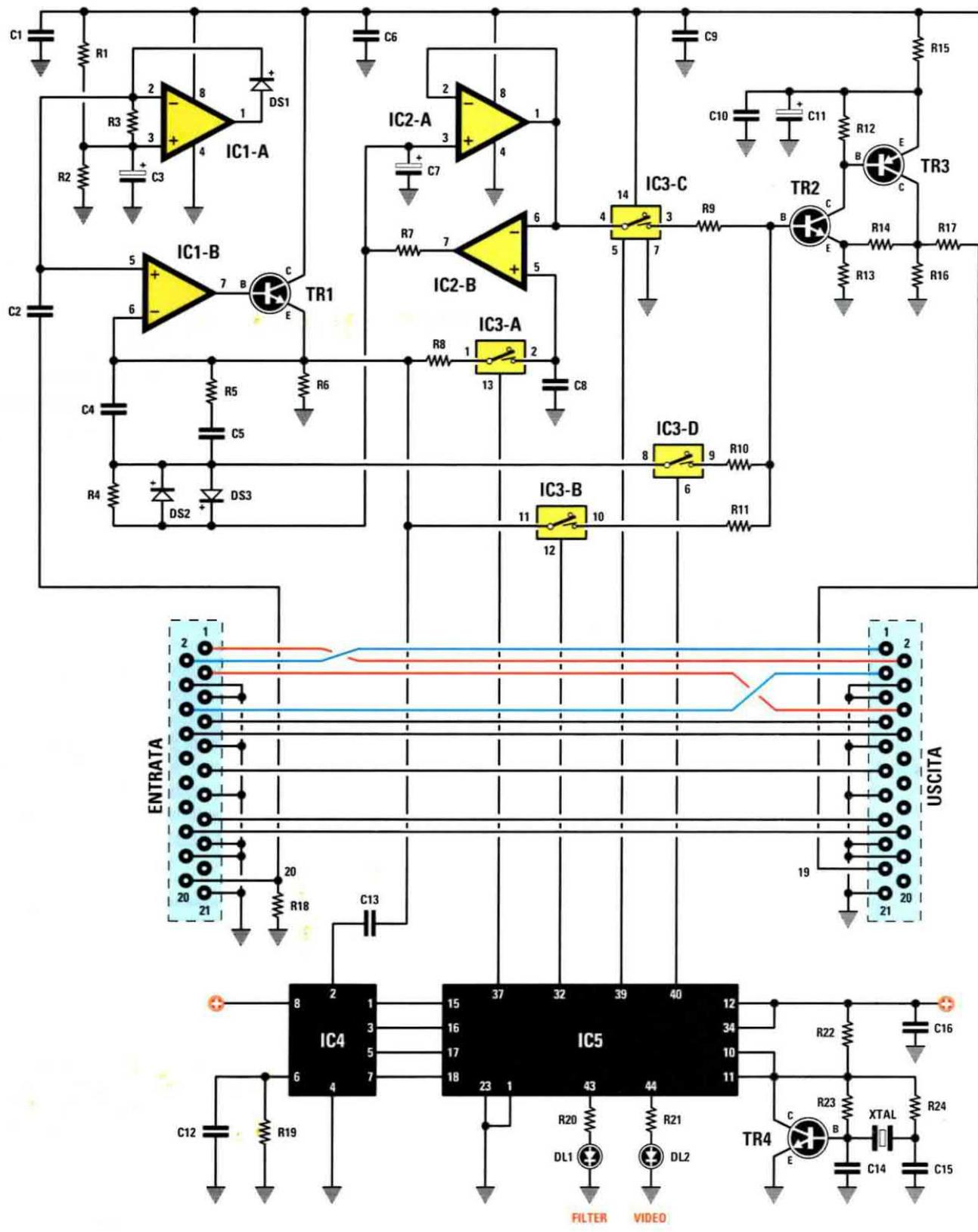
Fig.4 Schema elettrico del circuito "ammazza virus" che vi sarà utilissimo per ripulire i dischi DVD e i Nastri delle Videocassette. I terminali +, collegati al piedino 8 di IC4 e ai piedini 12-34 di IC5, vanno collegati sull'uscita + dello stadio alimentatore IC6.
