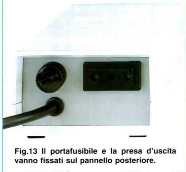
Fig.13 Il portafusibile e la presa d'uscita vanno fissati sul pannello posteriore.
