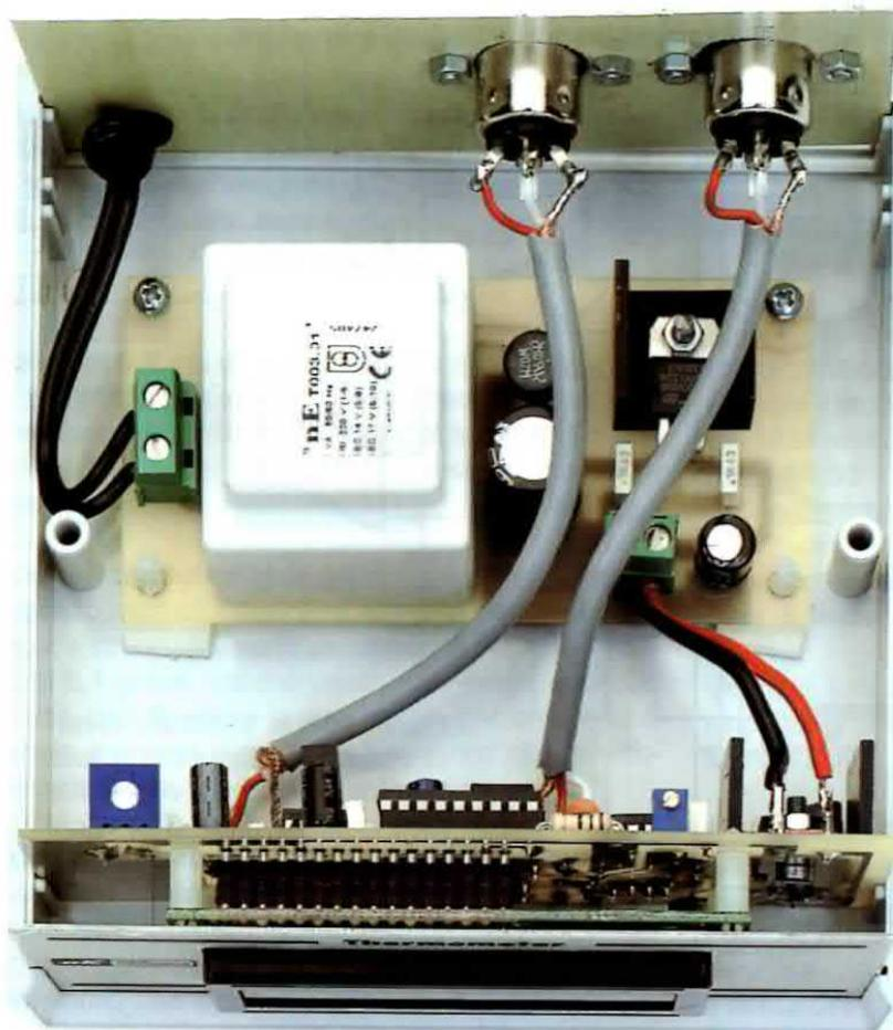
**Fig.12** In questa seconda foto si vede lo stadio di alimentazione fissato sul piano del mobile per mezzo di due viti autofilettanti e di due distanziatori plastici autoadesivi.
