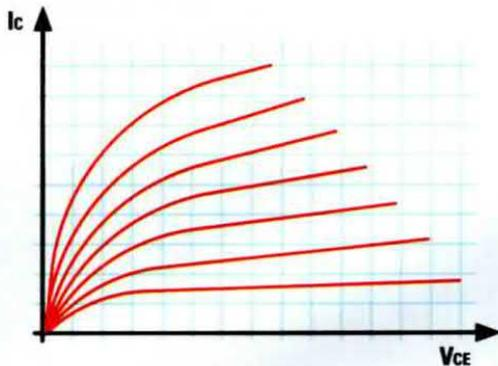
**Fig.3** Nella fig.2 abbiamo riportato le curve di un transistor di Bassa Potenza, mentre in questa figura riportiamo quelle di un transistor di Media Potenza, affinché possiate confrontarle e rilevarne le differenze.
