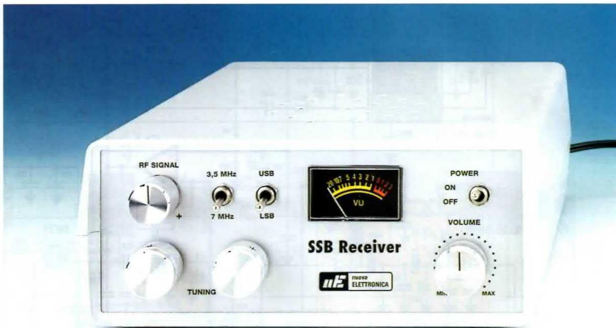
**Fig.11** Come si presenta il pannello frontale del ricevitore SSB per i 3,5 e i 7,0 MHz. Per la sintonia (vedi Tuning) abbiamo utilizzato due potenziometri: uno per la sintonia normale ed uno per la sintonia fine (vedi fig.20). Il potenziometro R1, indicato dalla scritta RF Signal, serve per attenuare i segnali che giungono molto forti.
