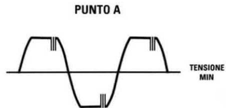
Fig.6 Quando ruotiamo il potenziometro R6 per ottenere in uscita la minima tensione, sul "punto A" di TRC1 rileviamo delle semionde squadrate con un numero molto ridotto d'impulsi presenti tutti sul lato destro. Il triac TRC2 s'innescia sul primo impulso posto a destra.
