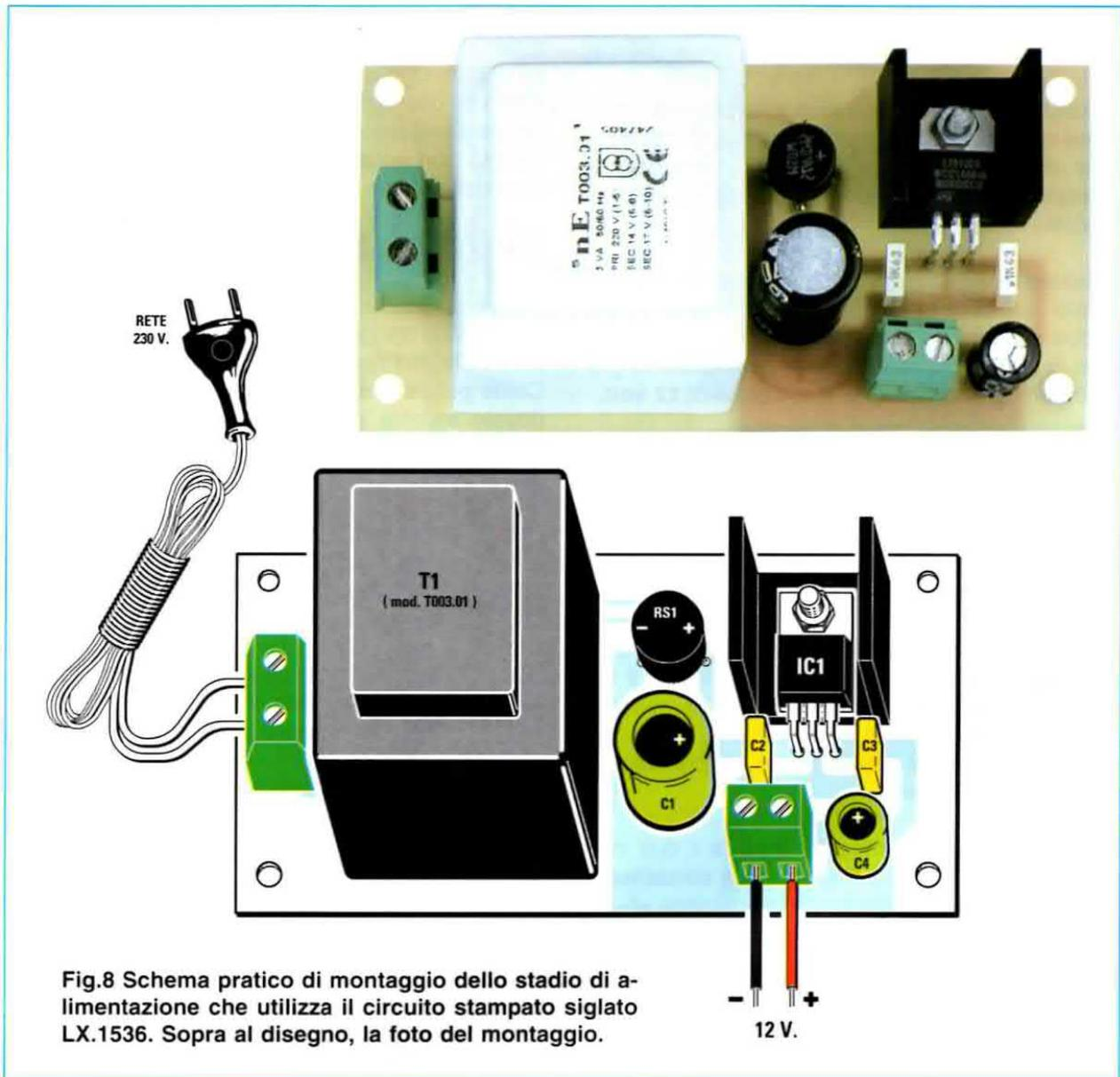
Fig.8 Schema pratico di montaggio dello stadio di alimentazione che utilizza il circuito stampato siglato LX.1536. Sopra al disegno, la foto del montaggio.
