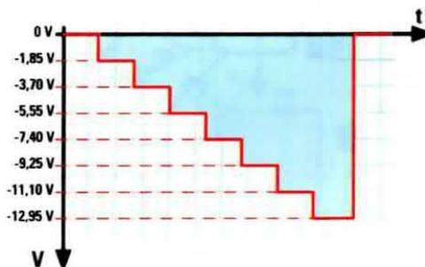
**Fig.8** Per testare i transistor NPN ci occorre una **rampa a 7 gradini** Negativa, che preleviamo dall'uscita di **IC3/B** (vedi fig.9).
