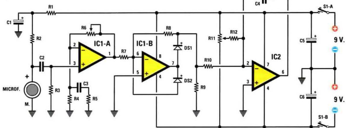
Fig.2 Schema elettrico del circuito. I due operazionali siglati IC1 e IC2 sono alimentati con una tensione duale di 9+9 volt che può essere ricavata da due normali pile radio.
