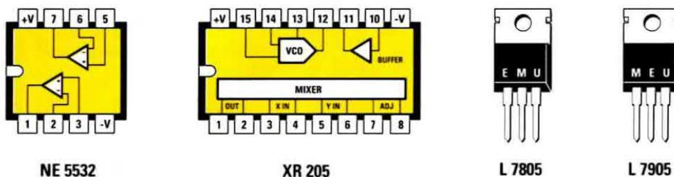
Fig.13 Sul lato sinistro del disegno le connessioni dei due integrati **NE.5532** e **XR.205** viste da sopra e con la tacca di riferimento a **U** rivolta verso sinistra. Sulla destra le connessioni dei due integrati stabilizzatori. Come potete notare le connessioni dell'integrato **L.7805** sono **E-M-U** e quelle dell'**L.7905** sono **M-E-U**.
