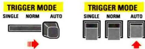
Fig.26 Sul pannello di ogni oscilloscopio c'è un selettore contraddistinto dalla scritta TRIGGER MODE. Questo selettore può essere del tipo a slitta (vedi disegno a sinistra) oppure a pulsanti (vedi disegno a destra). In entrambi i casi dovete spostare la levetta o premere il pulsante per attivare la funzione AUTO.
