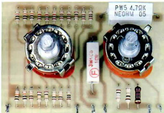
Fig.21 Foto dello stampato LX.1538/B con sopra già montati i due commutatori e le resistenze. Tenete presente che prima di inserire i due commutatori sul circuito stampato, dovete accorciare i loro perni utilizzando una sega da ferro. Le due resistenze a filo R52-R53 vanno tenute leggermente distanziate dal circuito stampato.
