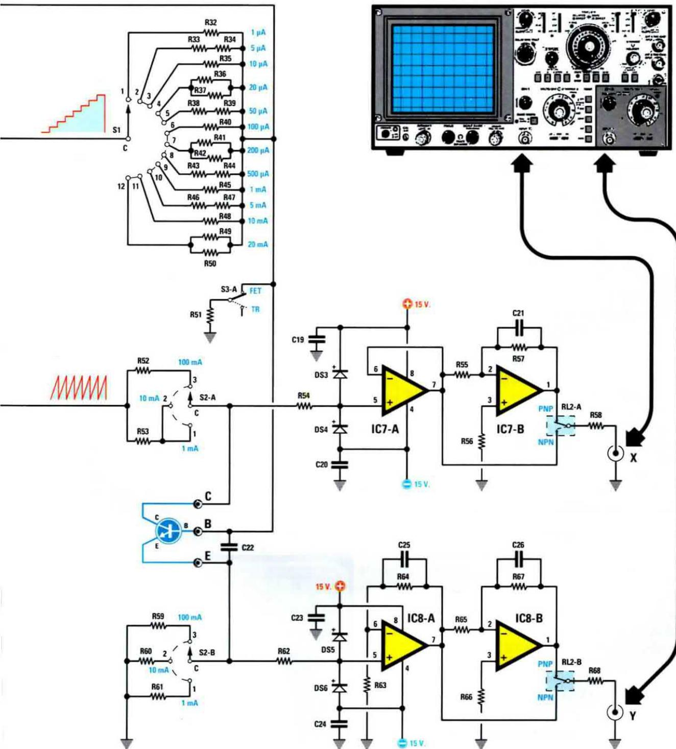
I terminali del Transistor da esaminare vanno collegati alle bocche C-B-E, corrispondenti a Collettore - Base - Emittitore, facendo attenzione a non invertirli. Per esaminare i Fet occorre semplicemente collegare il terminale Drain sulla boccia C, il terminale Gate sulla boccia B e il terminale Source sulla boccia E.
