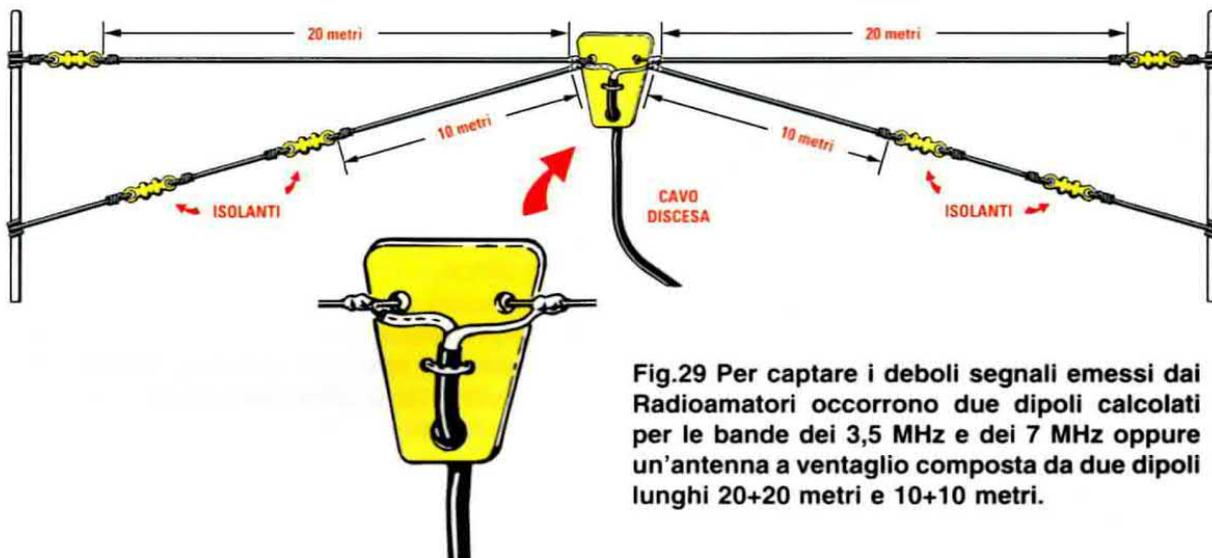
Fig.29 Per captare i deboli segnali emessi dai Radioamatori occorrono due dipoli calcolati per le bande dei 3,5 MHz e dei 7 MHz oppure un'antenna a ventaglio composta da due dipoli lunghi 20+20 metri e 10+10 metri.
