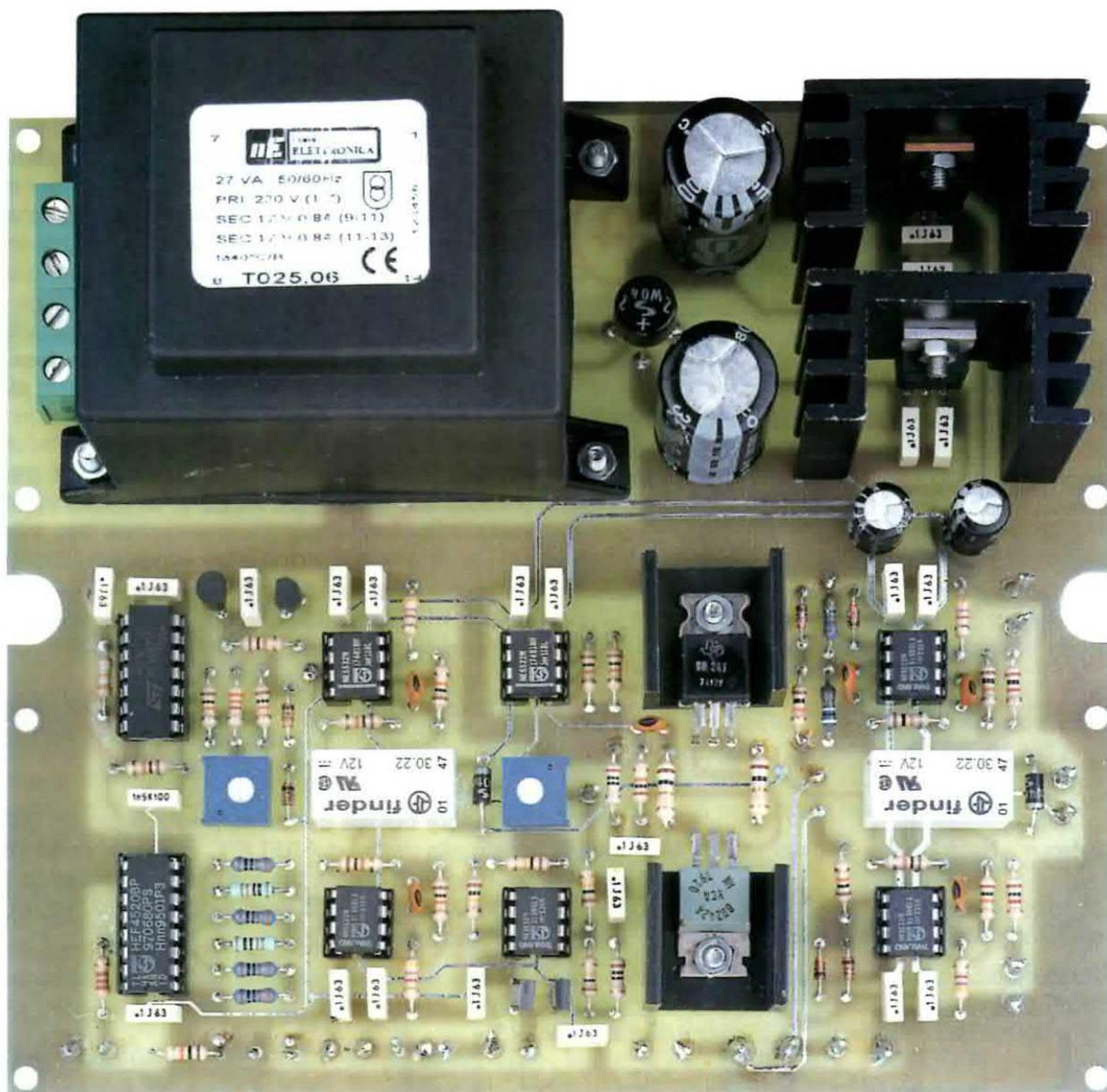
**Fig.18** In questa foto potete vedere come si presenta il circuito stampato LX.1538 dopo che sono stati montati tutti i componenti. Come si può notare, il circuito non presenta nessuna difficoltà di realizzazione e con l'aiuto dello schema pratico di fig.19, è anche facile sapere in quali posizioni collocare i vari componenti.
