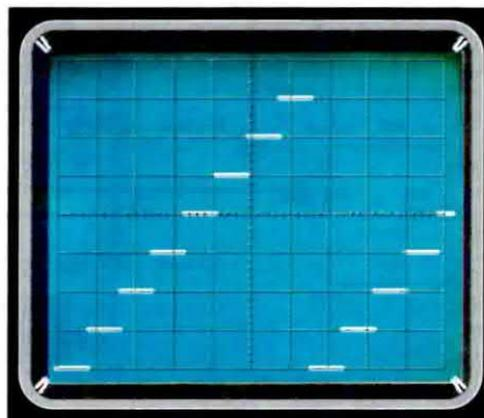
**Fig.10** Dopo aver collegato l'**oscilloscopio** sul test-point **TP1** (vedi fig.9), dobbiamo tarare il cursore del trimmer **R11** in modo da ottenere una rampa di 7 gradini, distanziati gli uni dagli altri esattamente di 1 volt. Sullo schermo dell'**oscilloscopio** verrà visualizzata una rampa formata da 8 trattini, come visibile nella foto a destra.
