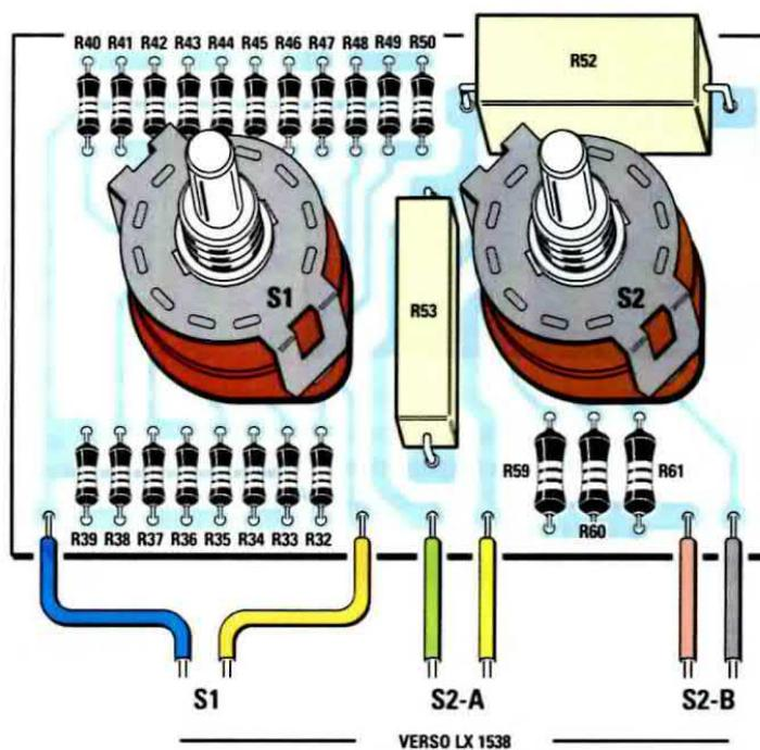
Fig.20 Sul circuito stampato LX.1538/B dovete inserire i due commutatori rotativi S1-S2 e tutte le resistenze che nell'elenco componenti sono precedute da un asterisco. I fili S1 - S2/A - S2/B, provenienti dal circuito stampato base LX.1538 (visibile a sinistra), devono essere collegati ai corrispondenti terminali del circuito stampato LX.1538/B.
