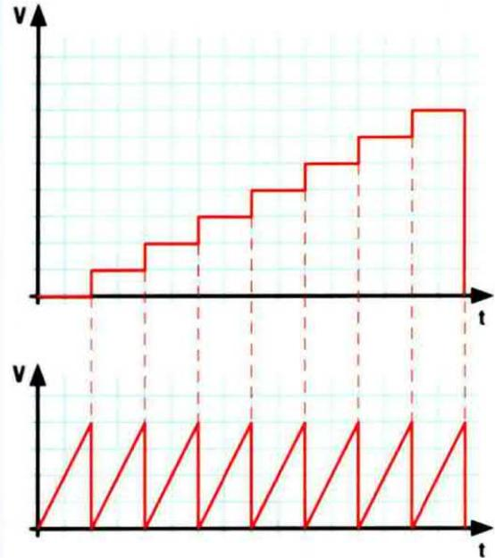
**Fig.5** Per realizzare un Tracciacurve sono necessarie due rampe perfettamente sincronizzate tra loro. La rampa a gradini, visibile nella parte superiore del disegno, serve per generare le 7 tracce corrispondenti alle correnti di Base, mentre la rampa a dente di sega serve per effettuare la scansione della tensione di Collettore.
