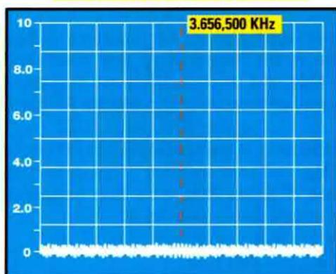
Fig.6 Se cerchiamo di vedere con un Analizzatore di Spettro il segnale emesso dal TX LX.1462, che è di  $3.200 + 456,5 = 3.656,5$  KHz (vedi fig.9), non lo vedremo mai, perché sprovvisto del segnale BF.
