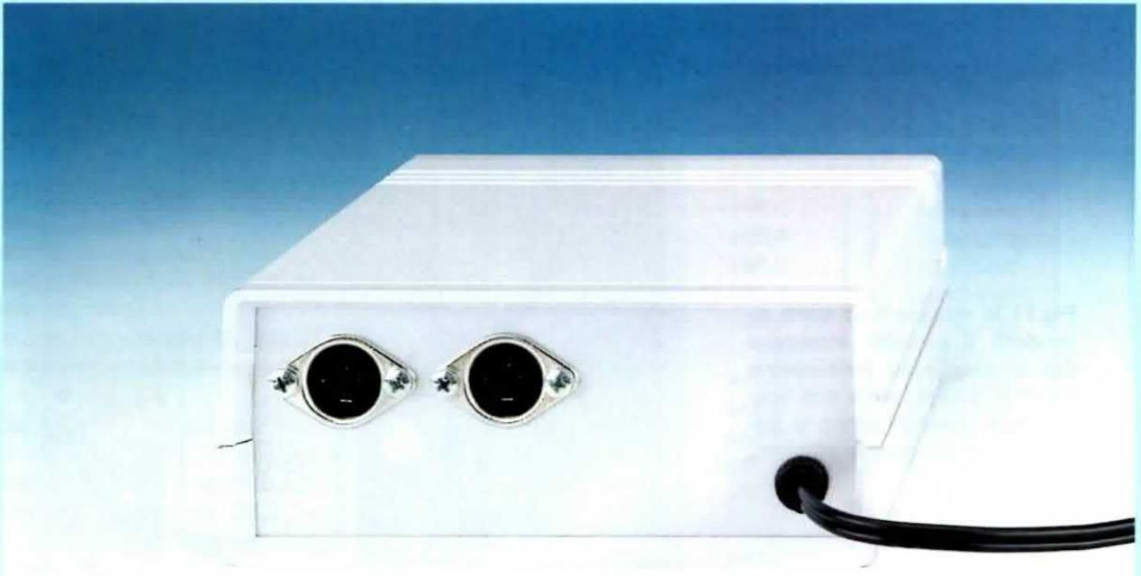
**Fig.13** Sul pannello posteriore del mobile vengono fissati i due connettori femmina necessari per innestare gli spinotti maschio visibili in fig.9. Non fate mai funzionare questo termometro per diverse decine di minuti senza nessun sensore collegato, perchè l'integrato A/D converter IC5 (MCP.3202) potrebbe surriscaldarsi e bruciarsi.
