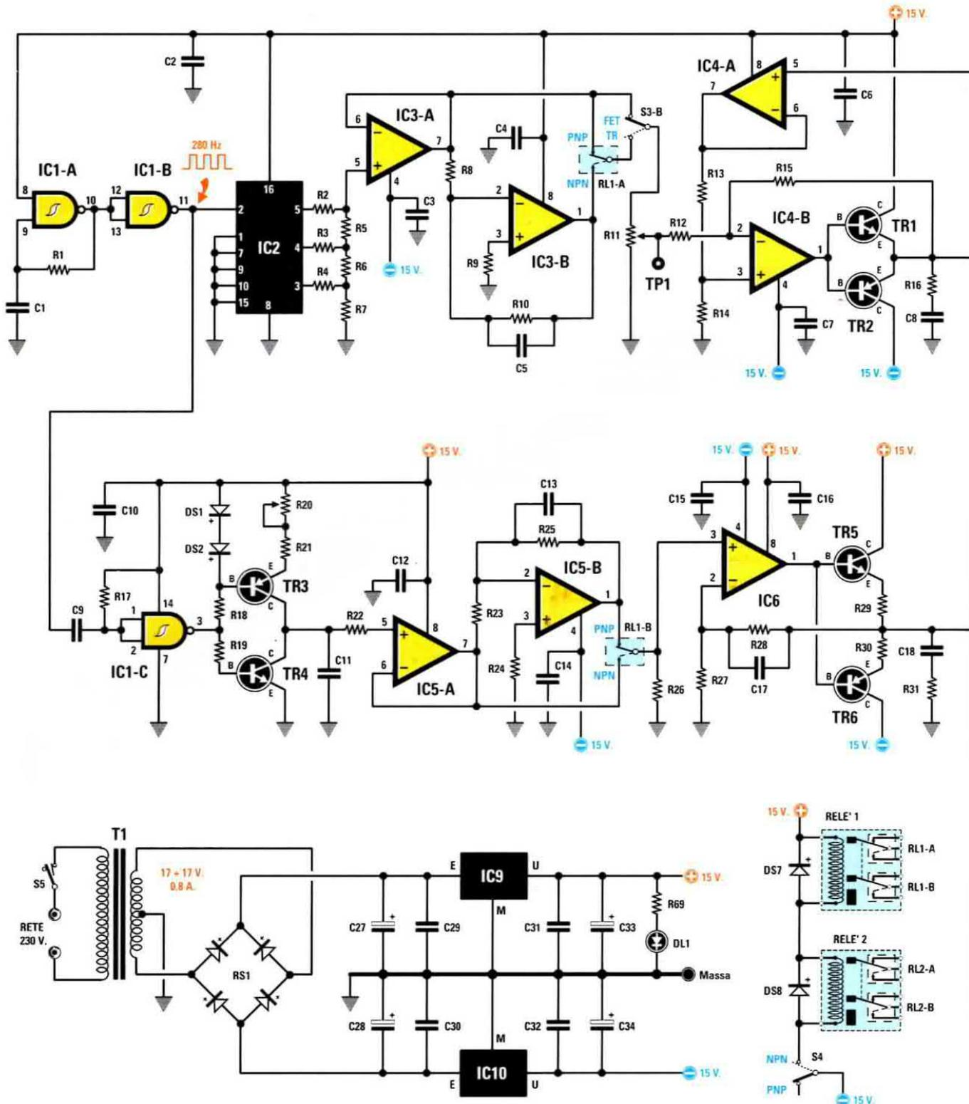
Fig.9 Schema elettrico del Tracciacurve completo dello stadio di alimentazione in grado di fornire una tensione duale di 15+15 volt. I due relè da 12 volt 2 scambi, visibili in basso a destra, permettono di effettuare la commutazione da NPN a PNP e viceversa, tramite il deviatore S4 posto sul pannello frontale del tracciacurve.
