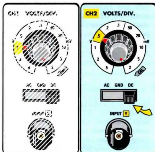
**Fig.40** Se volete testare subito un transistor qualsiasi, ruotate la manopola della Corrente di Collettore nella posizione 1 mA/div (vedi fig.36), quella del commutatore Volts/Div. del CH2 su 0,5 volt e, infine, spostate la levetta del selettore d'ingresso nella posizione DC.
