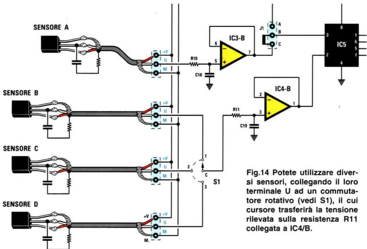
**Fig.14** Potete utilizzare diversi sensori, collegando il loro terminale U ad un commutatore rotativo (vedi S1), il cui cursore trasferirà la tensione rilevata sulla resistenza R11 collegata a IC4/B.
