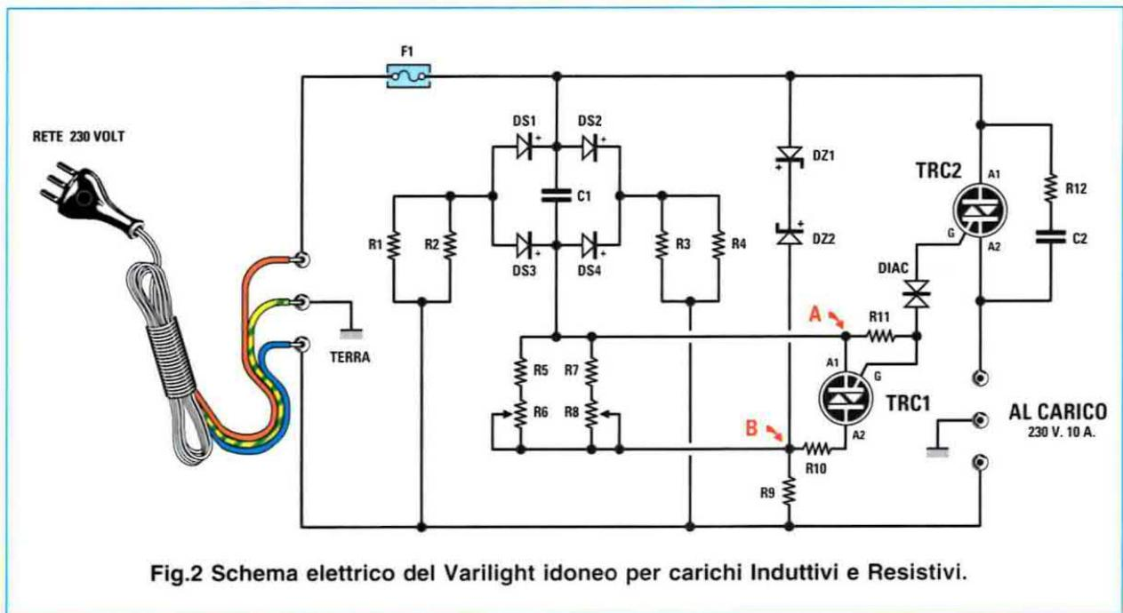
Fig.2 Schema elettrico del Varilight idoneo per carichi Induttivi e Resistivi.
