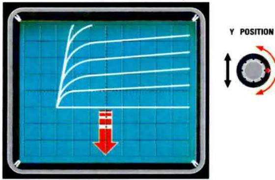
Fig.13 Se le 7 curve escono dalla parte superiore dell'oscilloscopio, possiamo riportarle nello schermo ruotando la manopola dello spostamento verticale.
