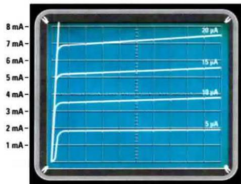
Fig.45 Se avete ruotato il commutatore VOLTS/DIV. del CH2 per la massima sensibilità, cioè a 0,1 volt, quasi sempre vedrete le tracce superiori uscire dallo schermo dell'oscilloscopio.
