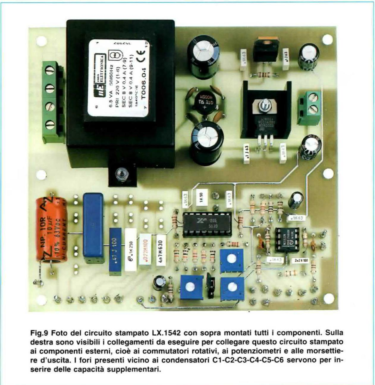
**Fig.9** Foto del circuito stampato LX.1542 con sopra montati tutti i componenti. Sulla destra sono visibili i collegamenti da eseguire per collegare questo circuito stampato ai componenti esterni, cioè ai commutatori rotativi, ai potenziometri e alle morsettiere d'uscita. I fori presenti vicino ai condensatori C1-C2-C3-C4-C5-C6 servono per inserire delle capacità supplementari.
