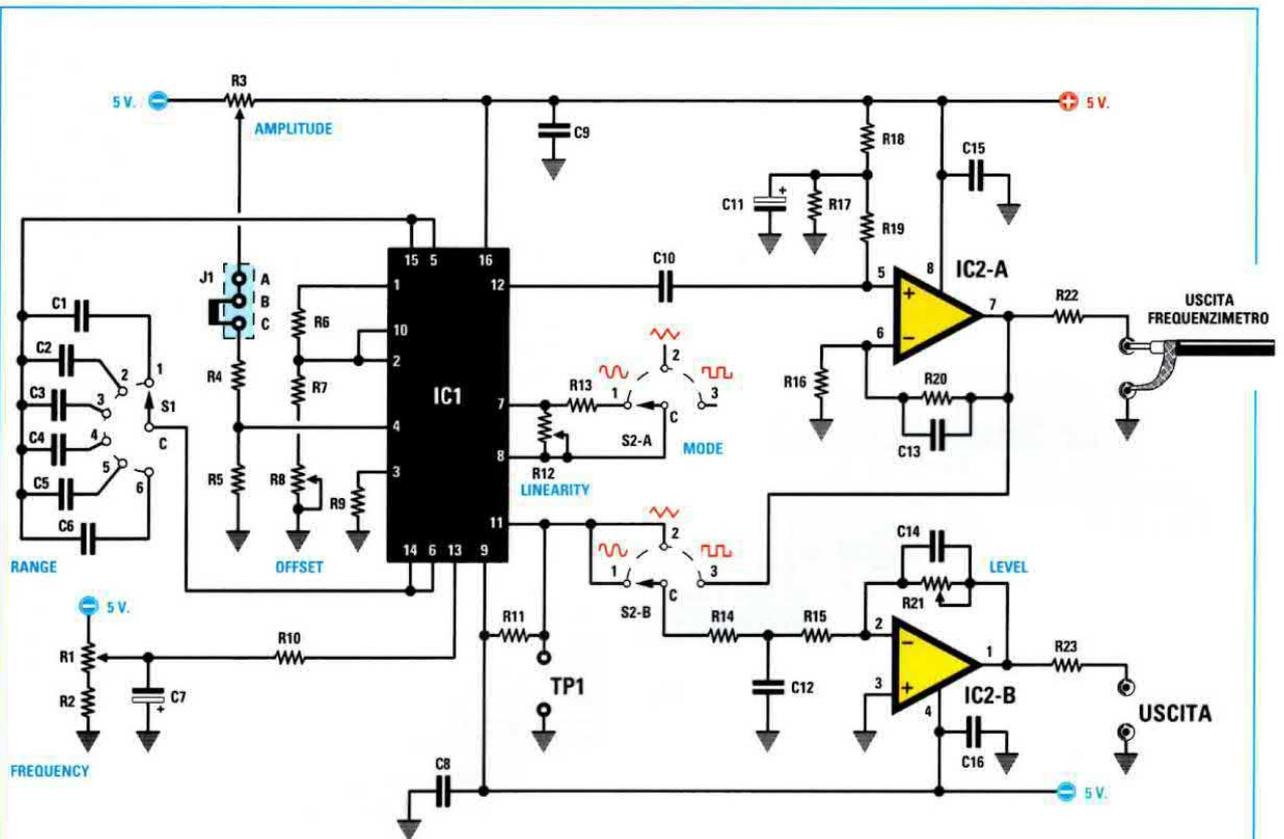
Fig.2 Schema elettrico del Generatore BF LX.1542. I valori di frequenza che abbiamo riportato nella Tabella N.1 sono puramente indicativi. Per modificarli basta variare il valore dei condensatori che risultano applicati sul commutatore S1. Per aumentare il valore della frequenza generata è sufficiente ridurre il valore della capacità, mentre per ridurla occorre solo aumentare il valore delle capacità da noi indicato.
