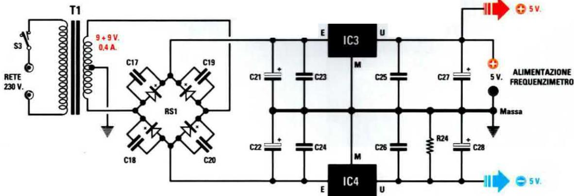
**Fig.3** Schema elettrico dello stadio di alimentazione duale che viene utilizzato per alimentare il **Generatore BF** di fig.2 ed il **Frequenzimetro digitale** di fig.4. L'elenco componenti di questo alimentatore è riportato nella pagina di sinistra.
