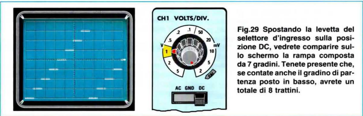
Fig.29 Spostando la levetta del selettore d'ingresso sulla posizione DC, vedrete comparire sullo schermo la rampa composta da 7 gradini. Tenete presente che, se contate anche il gradino di partenza posto in basso, avrete un totale di 8 trattini.
