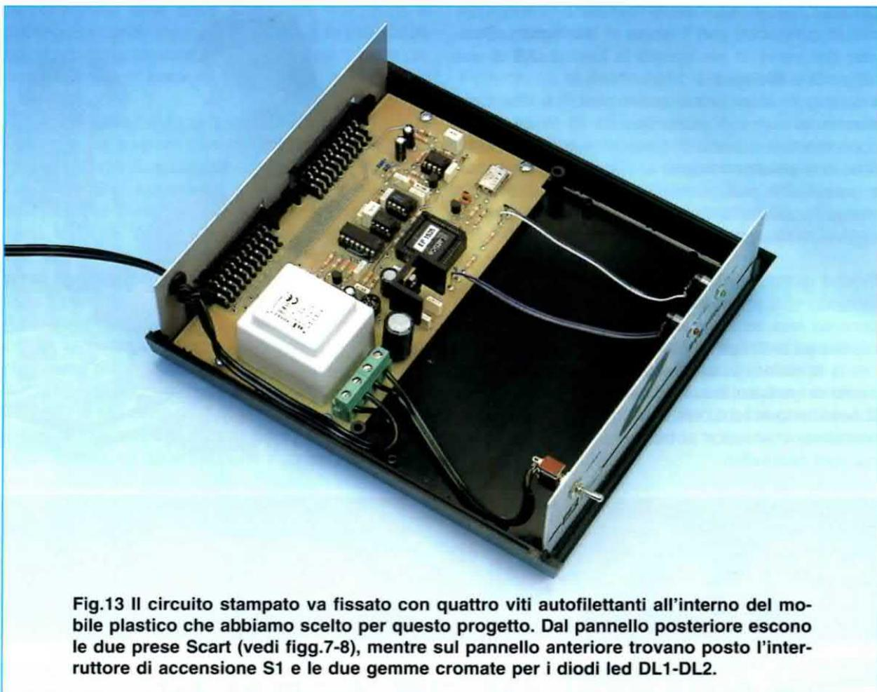
**Fig.13** Il circuito stampato va fissato con quattro viti autofilettanti all'interno del mobile plastico che abbiamo scelto per questo progetto. Dal pannello posteriore escono le due prese Scart (vedi figg.7-8), mentre sul pannello anteriore trovano posto l'interruttore di accensione S1 e le due gemme cromate per i diodi led DL1-DL2.
