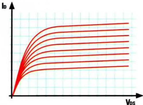
**Fig.4** Diversamente dalle figg.2-3, questa curva presenta 8 tracce e non 7, perché è generata da un FET e non da un Transistor. Anche i terminali D-G-S dei Fet vanno collegati alle boccole C-B-E.
