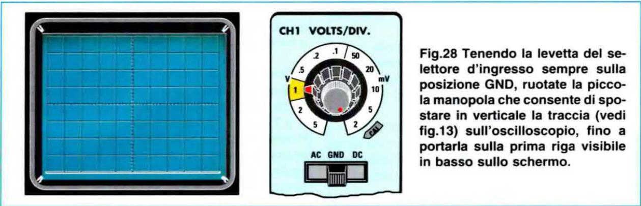
Fig.28 Tenendo la levetta del selettore d'ingresso sempre sulla posizione GND, ruotate la piccola manopola che consente di spostare in verticale la traccia (vedi fig.13) sull'oscilloscopio, fino a portarla sulla prima riga visibile in basso sullo schermo.
