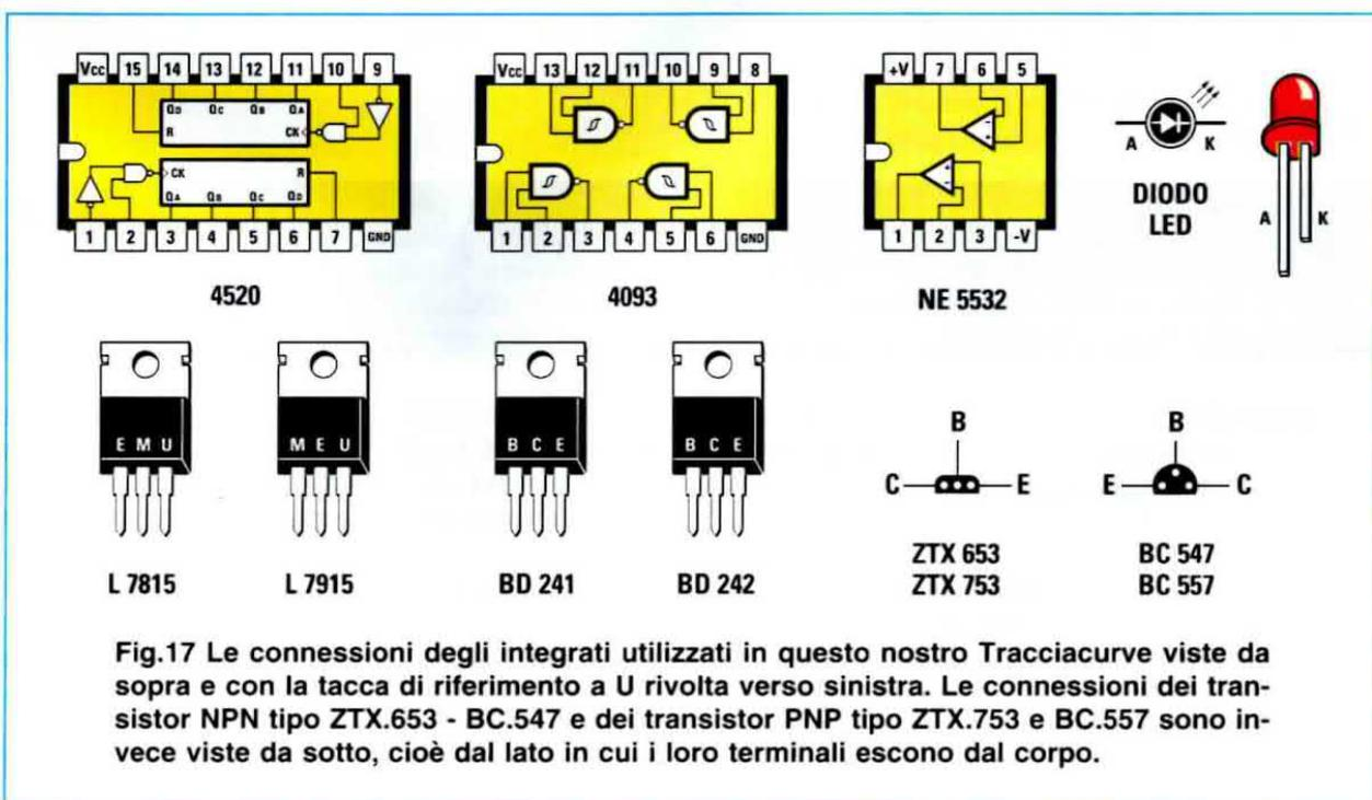
Fig.17 Le connessioni degli integrati utilizzati in questo nostro Tracciacurve viste da sopra e con la tacca di riferimento a U rivolta verso sinistra. Le connessioni dei transistor NPN tipo ZTX.653 - BC.547 e dei transistor PNP tipo ZTX.753 e BC.557 sono invece viste da sotto, cioè dal lato in cui i loro terminali escono dal corpo.
