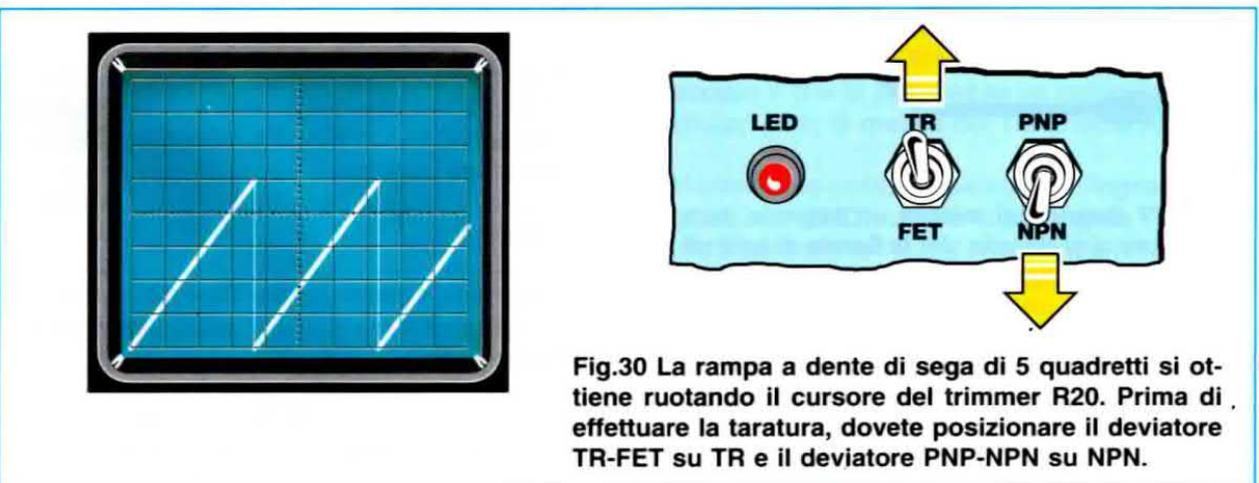
Fig.30 La rampa a dente di sega di 5 quadretti si ottiene ruotando il cursore del trimmer **R20**. Prima di effettuare la taratura, dovete posizionare il deviatore **TR-FET** su **TR** e il deviatore **PNP-NPN** su **NPN**.
