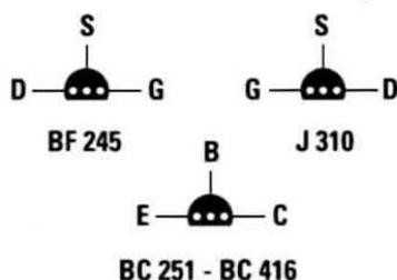
Fig.2 Connessioni viste da sotto dell'integrato, del fet e del transistor viste da sopra, tutti utilizzati in questo circuito.
