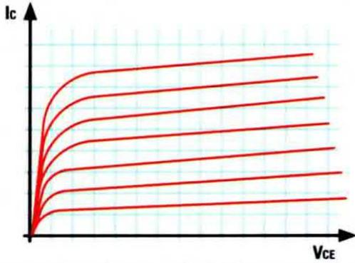
**Fig.2** Se sulle boccole C-B-E applichiamo i terminali di un Transistor, sullo schermo dell'oscilloscopio vediamo una serie di curve che variano al variare del tipo di transistor che andiamo a testare.
