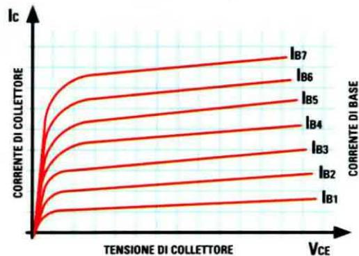
**Fig.6** Le curve che otteniamo dal controllo di qualsiasi transistor, ci consentono di studiare come varia la Corrente di Collettore al variare della Corrente di Base. Come potete vedere in questa figura, la Corrente di Collettore è riportata sull'asse Verticale, mentre i 7 valori della Corrente di Base sono rappresentati da altrettante curve contrassegnate da  $I_{b1}$  a  $I_{b7}$ . Sull'asse Orizzontale è invece visualizzata la scansione della Tensione di Collettore.
