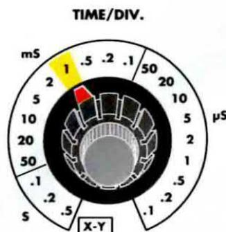
Fig.32 Per ottenere sullo schermo la **rampa a dente di sega** di fig.30, dovete inoltre ruotare il commutatore **TIME/DIV.** sulla posizione **1 mS**, pari a **1 millisecondo**.
