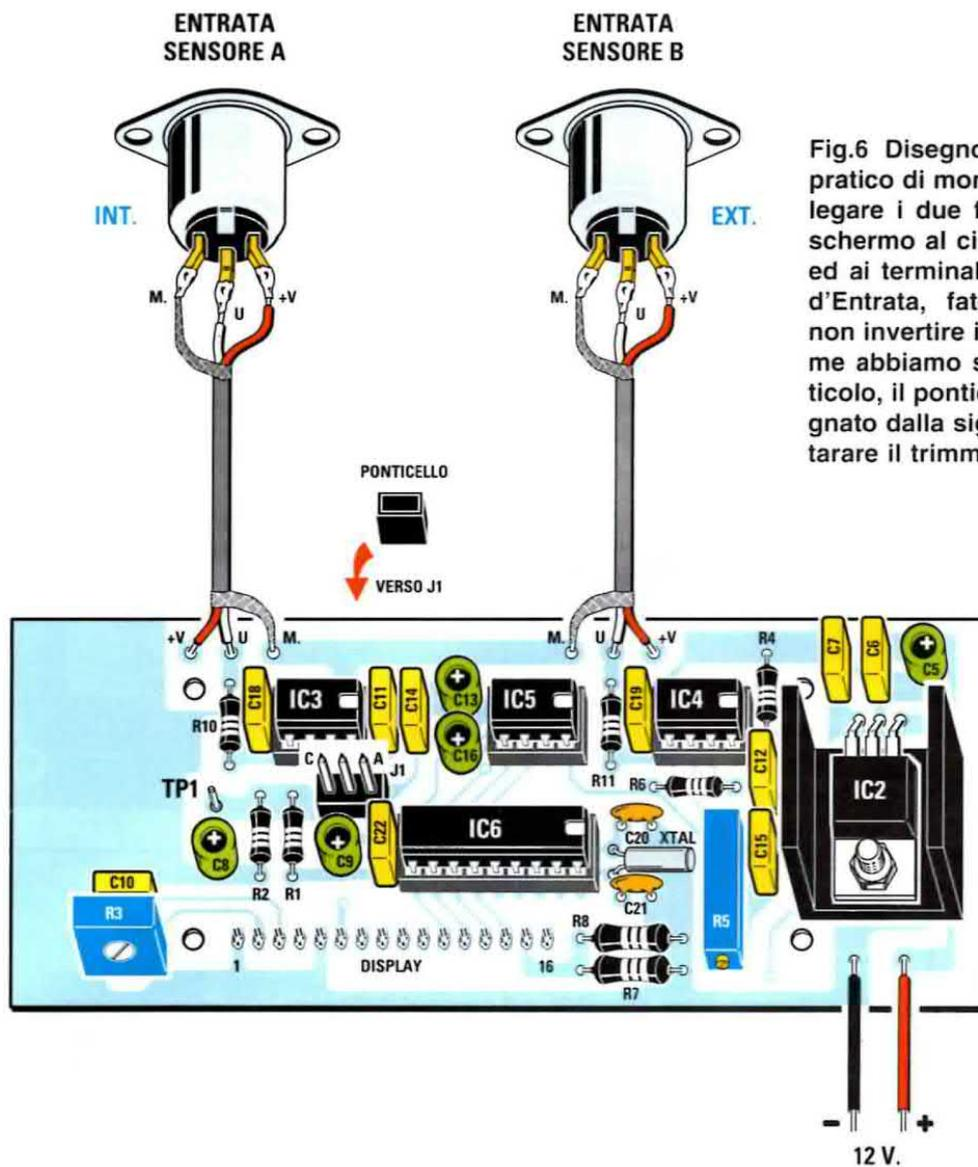
Fig.6 Disegno dello schema pratico di montaggio. Nel collegare i due fili e la calza di schermo al circuito stampato ed ai terminali dei connettori d'Entrata, fate attenzione a non invertire i fili M U +V. Come abbiamo spiegato nell'articolo, il ponticello contrassegnato dalla sigla J1 serve per tarare il trimmer R5.
