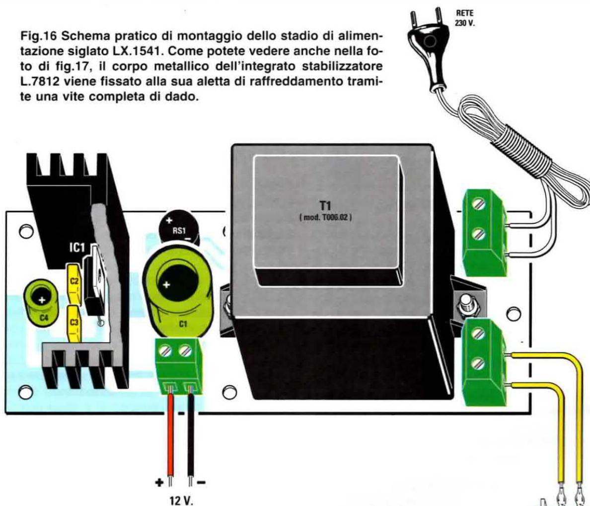
Fig.17 Qui sotto la foto dello stadio di alimentazione che vi fornirà la richiesta tensione stabilizzata di 12 volt. Per evitare errori, ricordatevi che la tensione Positiva esce dal foro di sinistra della morsetteria. Questo stadio va bloccato sul piano del mobile plastico (vedi fig.19) utilizzando 5 distanziatori plastici provvisti di base autoadesiva.
