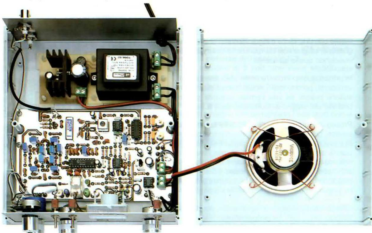
Fig.19 In questa foto potete vedere come viene fissato sul piano del mobile il circuito stampato del ricevitore e quello dell'alimentatore. L'altoparlante può essere collocato esternamente oppure fissato all'interno sul coperchio del mobile (vedi fig.27).
