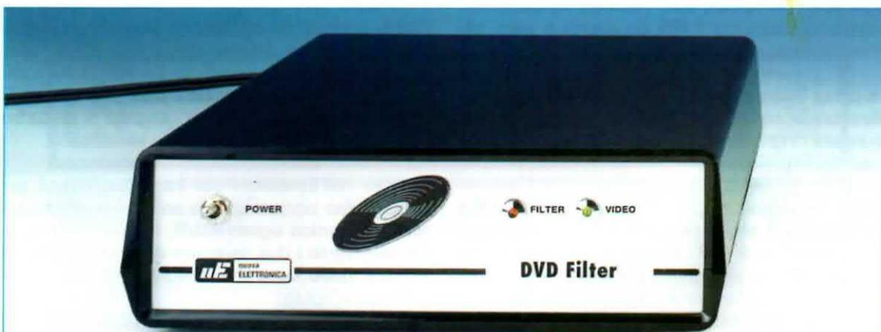
Fig.1 Il circuito per eliminare i "virus" è racchiuso in un elegante mobile plastico. Dal retro del mobile escono le prese Scart d'Entrata e d'Uscita (vedi fig.8), mentre sul pannello frontale ci sono un led Verde, che si accende quando il circuito è in funzione, e un led Rosso, che si accende quando il circuito ha individuato un "virus" e lo ha eliminato.
