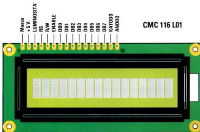
Fig.6 Sulla parte superiore del display LCD sono presenti 16 piste forate da utilizzare per inserire i terminali del doppio connettore maschio visibile in fig.16.
