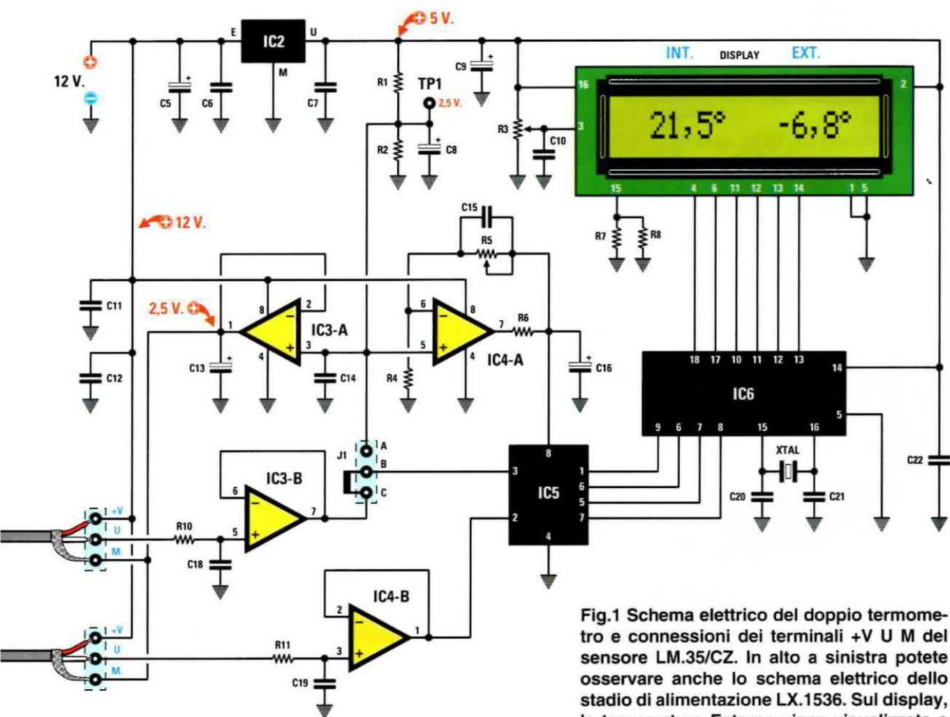
Fig.1 Schema elettrico del doppio termometro e connessioni dei terminali +V U M del sensore LM.35/CZ. In alto a sinistra potete osservare anche lo schema elettrico dello stadio di alimentazione LX.1536. Sul display, la temperatura Esterna viene visualizzata a destra e quella Interna a sinistra.
