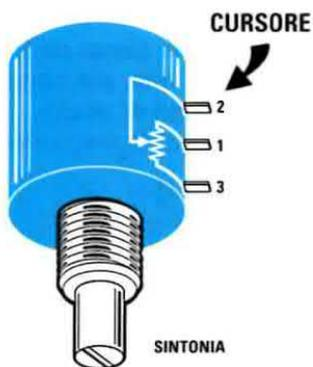
Fig.26 Nel disegno a sinistra potete vedere le connessioni interne del potenziometro R27. A differenza di altri potenziometri, che hanno il loro cursore al centro, in quello a multitigri il cursore risulta posto verso il fondo (vedi terminale 2), quindi, quando lo collegate al circuito stampato, rispettate le connessioni visibili in fig.20.
