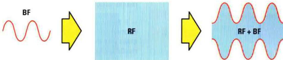
Fig.1 Per trasmettere in AM, si somma il segnale di BF alla portante RF dello stadio trasmettente e in questo modo si ottiene un segnale composto da RF+BF.
