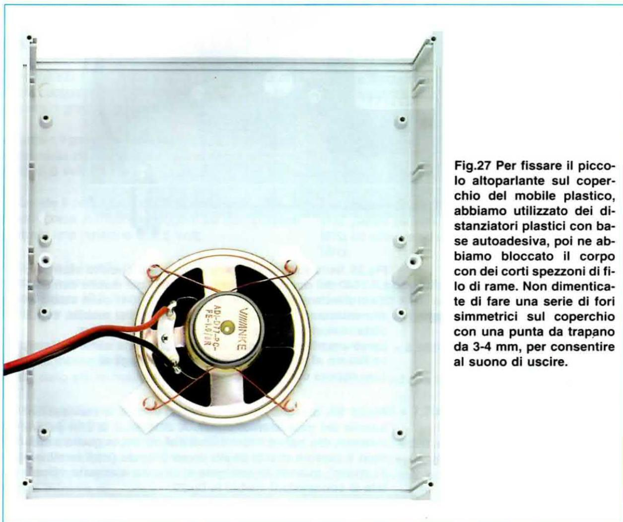
**Fig.27** Per fissare il piccolo altoparlante sul coperchio del mobile plastico, abbiamo utilizzato dei distanziatori plastici con base autoadesiva, poi ne abbiamo bloccato il corpo con dei corti spezzoni di filo di rame. Non dimenticate di fare una serie di fori simmetrici sul coperchio con una punta da trapano da 3-4 mm, per consentire al suono di uscire.
