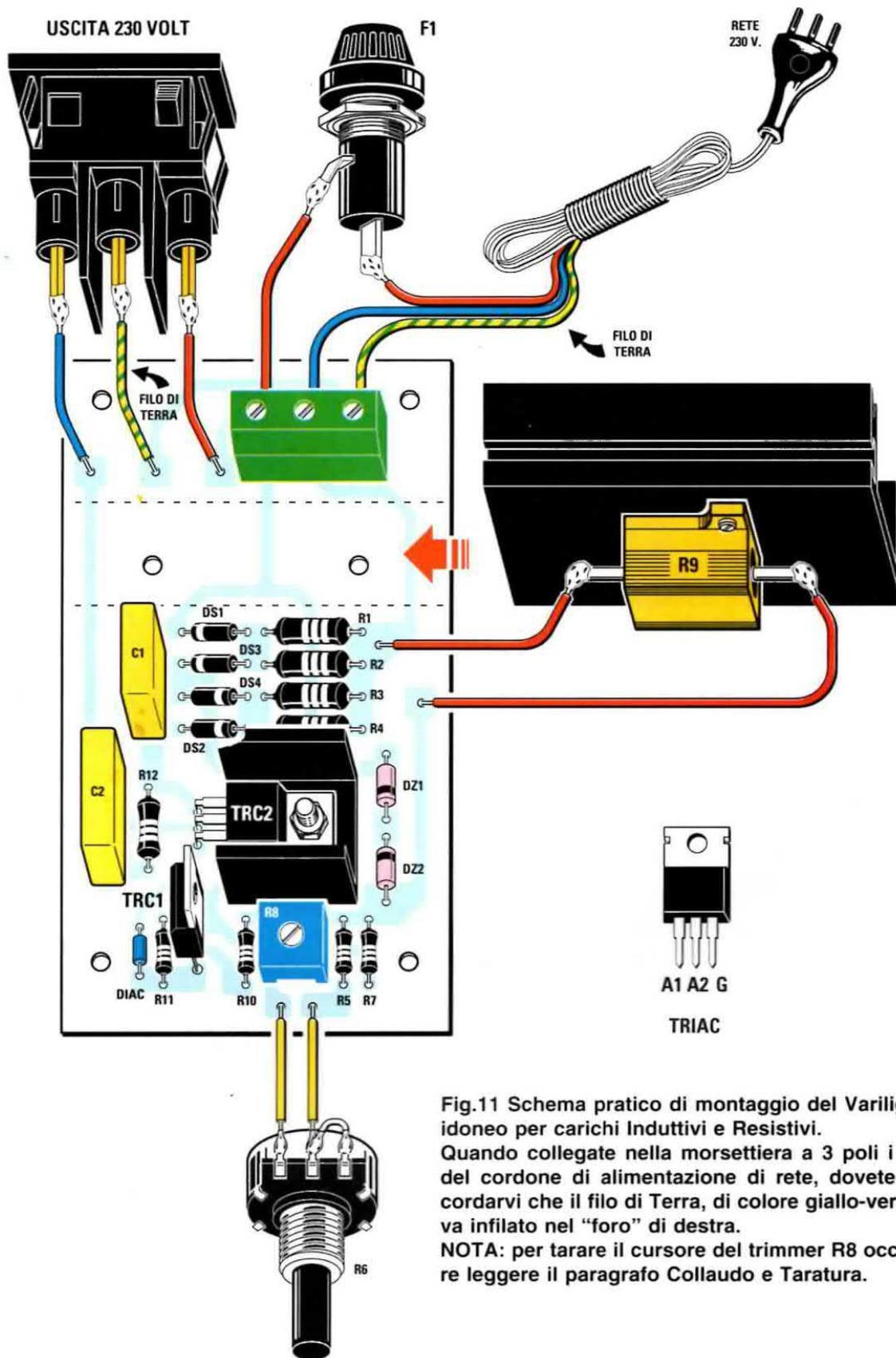
Fig.11 Schema pratico di montaggio del Varilight idoneo per carichi Induttivi e Resistivi. Quando collegate nella morsettiera a 3 poli i fili del cordone di alimentazione di rete, dovete ricordarvi che il filo di Terra, di colore giallo-verde, va infilato nel "foro" di destra. NOTA: per tarare il cursore del trimmer R8 occorre leggere il paragrafo Collaudo e Taratura.
