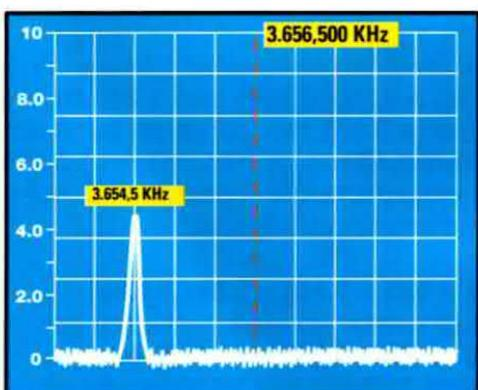
Fig.8 Se moduliamo in LSB i 3.656,5 KHz con un segnale BF di 2 KHz, noi vediamo sullo schermo una sola portante RF sulla frequenza di  $3.656,5 - 2 = 3.654,5$  KHz, come riportato nel trasmettitore di fig.9.
