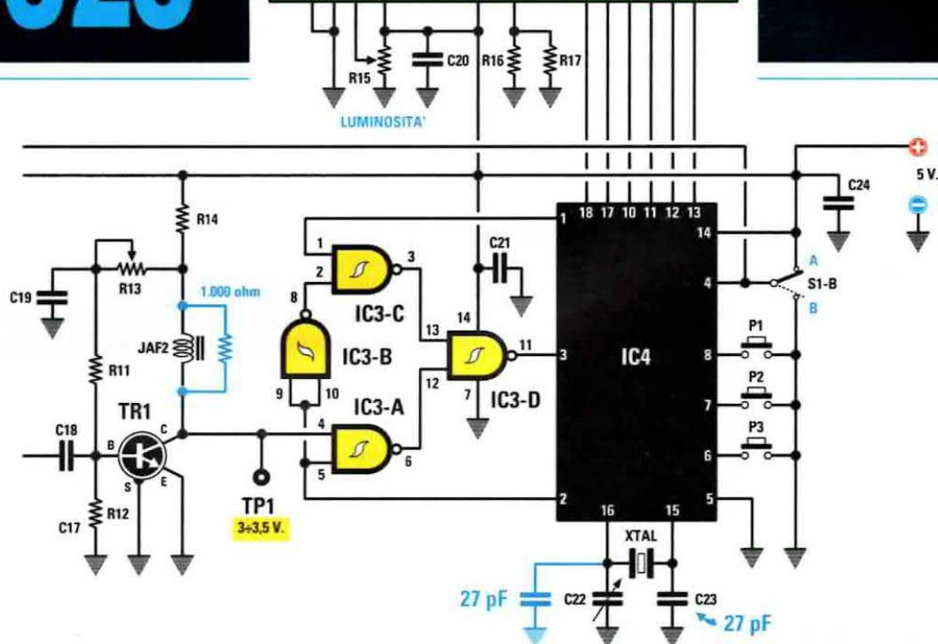
Fig.1 Per correggere la tolleranza del quarzo XTAL collegato ai piedini 16-15 di IC4 si dovrà sostituire il condensatore C23 che ora risulta da 4,7 pF con uno da 27 pF, poi applicare in parallelo al compensatore C22 da 6 pF un secondo condensatore ceramico da 27 pF. In tutti i kits che forniremo d'ora in poi abbiamo sostituito il compensatore C22 da 6 pF di colore Bianco con uno da 27 pF caratterizzato dal corpo di colore Rosso.
