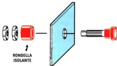
Fig.46 Foto dell'interno del Tracciacurve visto dalla parte frontale. Prima di fissare le boccole C-B-E sul pannello frontale, dovete ricordarvi di sfilare totalmente dal loro corpo la rondella isolante posteriore, che infilerete sul retro del perno, in modo da isolare il metallo della boccola da quello del pannello onde evitare cortocircuiti.
