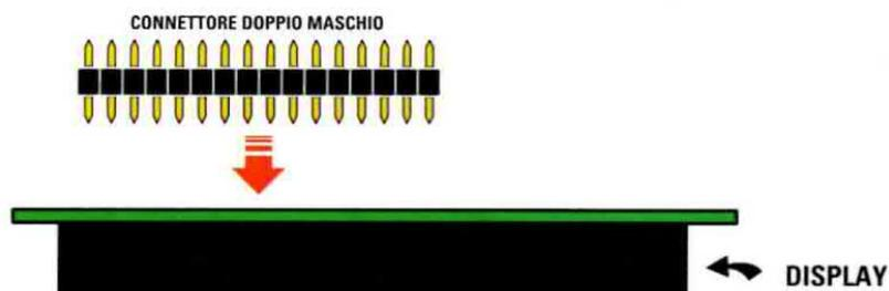
Fig.3 La prima operazione da compiere sarà quella di prendere il doppio connettore maschio incluso nel kit ed inserire i 16 terminali presenti su un suo lato nei fori presenti sul bordo superiore del display LCD. Dopo averli innestati a fondo, dovete saldarli facendo attenzione a non cortocircuitare due piste adiacenti. Nella foto visibile nella pagina di sinistra potete notare come sono "pulite" queste saldature.
