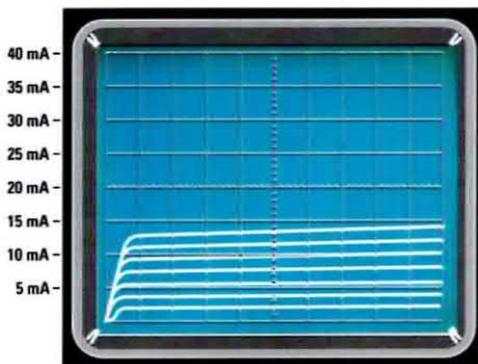
Fig.43 Se avete ruotato il commutatore VOLTS/DIV. del CH2 per una sensibilità bassa, ad esempio a 0,5 volt, sullo schermo vedrete 7 tracce, ma troppo ravvicinate, quindi poco comprensibili.
