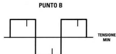
Fig.7 Quando dall'uscita preleviamo la minima tensione, sul "punto B", che si trova in corrispondenza della giunzione R9-R10, ritroviamo delle onde quadre il cui IMPULSO di eccitazione è ora posizionato a destra e non più a sinistra, come risulta visibile in fig.4.
