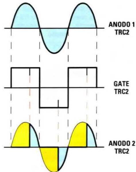
Fig.8 Quando il potenziometro R6 è ruotato per fornire in uscita la minima tensione, l'impulso di eccitazione giunge sul Gate del triac TRC2 quasi al termine del ciclo di ogni semionda (vedi impulso sulle onde quadre). In queste condizioni il Triac si porta in conduzione in ritardo fornendo in uscita delle sinusoidi incomplete.
