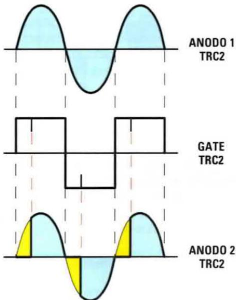
Fig.5 Quando il potenziometro R6 è ruotato per fornire in uscita la massima tensione, l'impulso di eccitazione giunge sul Gate del triac TRC2 all'inizio del ciclo delle semionde (vedi impulso sulle onde quadre). In queste condizioni il Triac si porta subito in conduzione fornendo in uscita delle sinusoidi quasi complete.
