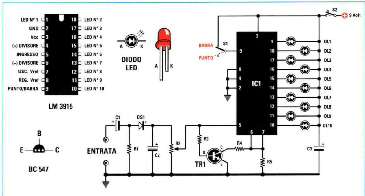
Fig.1 Qui sopra, schema elettrico di questo Vu-Meter e connessioni dell'integrato LM.3915 viste da sopra e con la tacca di riferimento orientata verso l'alto, del transistor BC.547 viste da sotto e dei diodi. Il terminale più lungo dei diodi led indicato A-nodo va rivolto verso il positivo di alimentazione. Qui sotto, elenco dei componenti.
