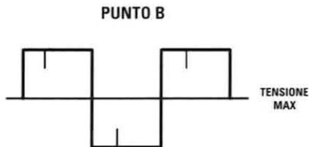
Fig.4 Quando dall'uscita preleviamo la massima tensione, sul "punto B", che si trova in corrispondenza della giunzione R9-R10, ritroviamo delle onde quadre al cui interno è presente l'IMPULSO di eccitazione. Questo impulso si trova tutto a sinistra, all'inizio di ogni semionda.
