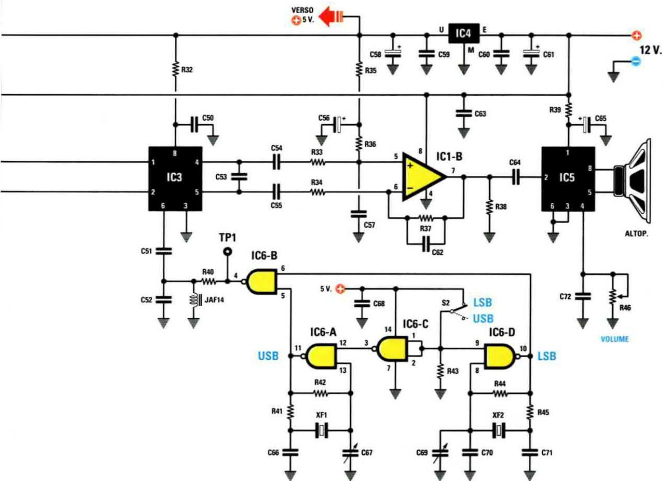
In questa parte dello schema elettrico troviamo i due oscillatori USB - LSB. Il Nand siglato IC6/A viene utilizzato per generare la frequenza USB dei 456,5 KHz, mentre il Nand IC6/D per generare la frequenza LSB dei 453,5 KHz.
