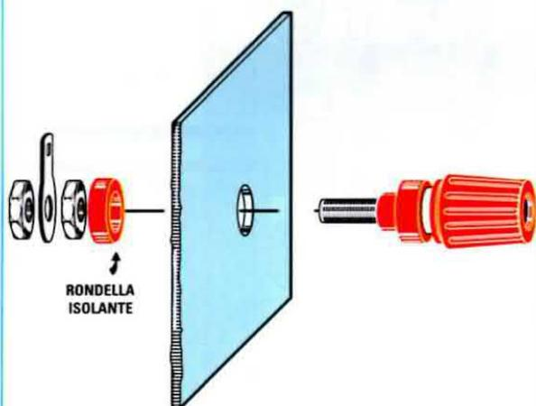
Fig.12 Prima di fissare le morsettiere per l'uscita del segnale BF, dovete sfilare i dadi e la rondella di plastica posti sul retro del pannello, poi infilare il corpo della morsettiere nel pannello frontale, per poi reinserire dal retro la rondella in plastica e stringere il tutto con i due dadi.
