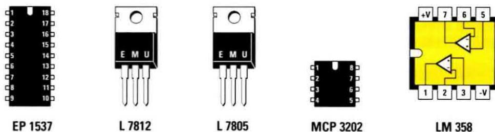
Fig.10 Connessioni viste da sopra della eprom programmata EP.1537 e dei due integrati MCP.3202 e LM.358 viste da sopra. Quando inserite questi integrati nel circuito stampato, dovete rivolgere verso destra la loro tacca di riferimento a U come visibile in fig.6. Le connessioni dei due integrati siglati L.7812-L.7805 sono identiche.
