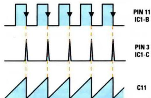
Fig.16 La **rampa a dente di sega** viene ricavata dalla frequenza di **Clock** a **280 Hz** presente sul piedino 11 di **IC1/B**. In corrispondenza di ciascun fronte di discesa del **Clock**, sul piedino 3 di **IC1/C** abbiamo un **impulso** che viene utilizzato per ottenere la nostra **rampa a dente di sega**.
