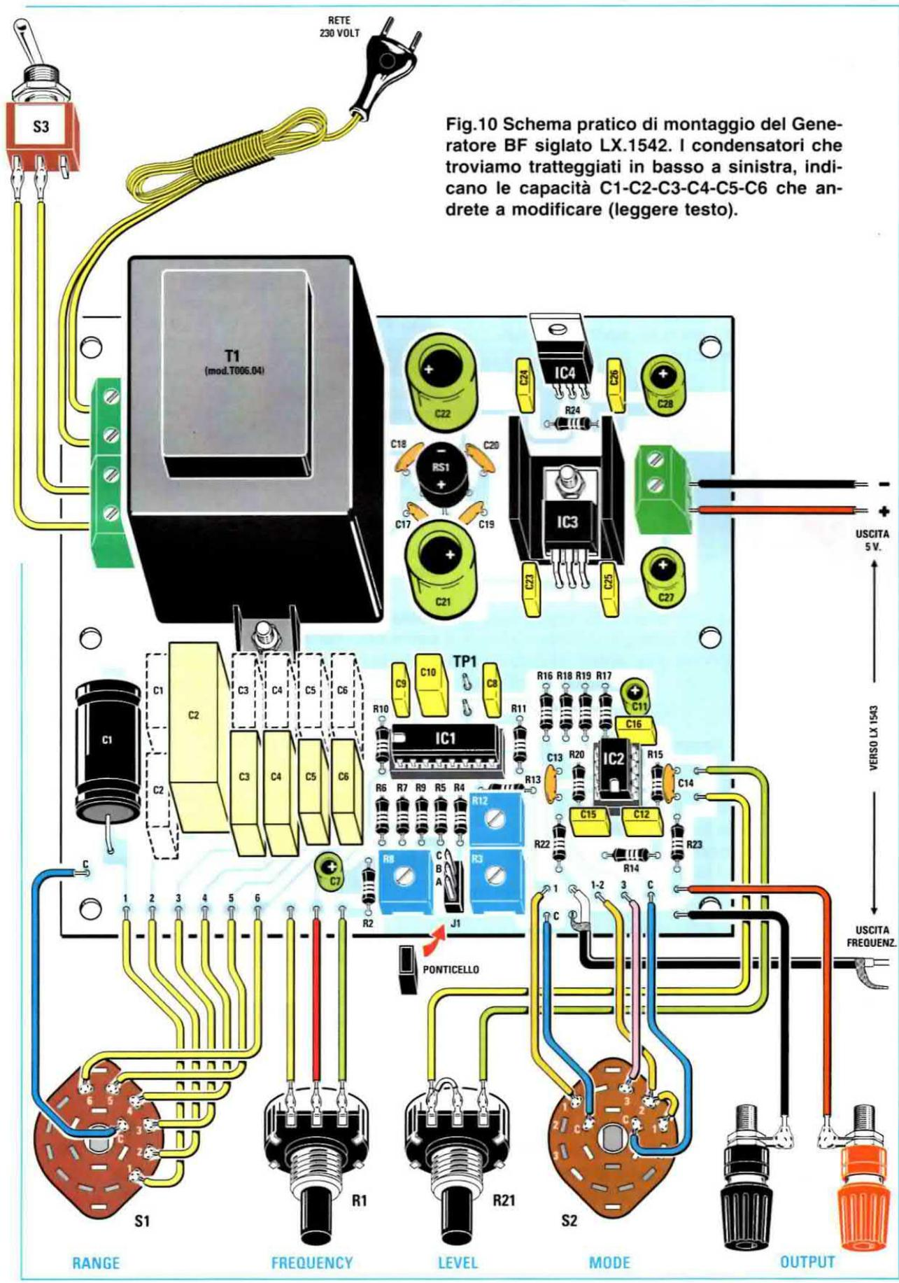
Fig.10 Schema pratico di montaggio del Generatore BF siglato LX.1542. I condensatori che troviamo tratteggiati in basso a sinistra, indicano le capacità C1-C2-C3-C4-C5-C6 che andrete a modificare (leggere testo).
