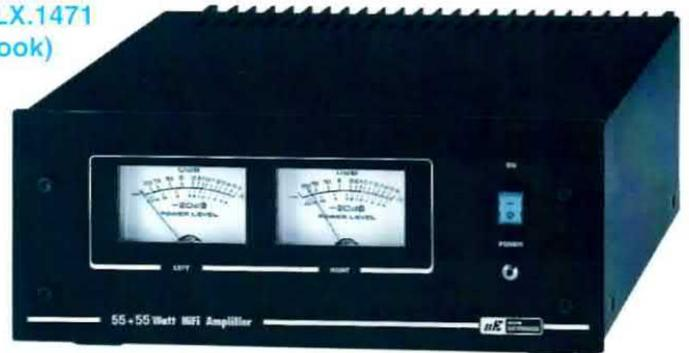
Questo finale **Stereo Hi-Fi** utilizza due coppie di Darlington **TIP.142** e **TIP.147** ed è in grado di erogare una potenza **musicale** di **110+110 watt** se alimentato con una tensione **duale** di **38+38 volt**. Se qualcuno dovesse trovare eccessivi questi **110+110 watt Stereo**, potrebbe ridurli semplicemente alimentando lo stadio finale con una tensione di **28+28 volt (80+80 watt)** o di **25+25 volt (70+70 watt)**.
