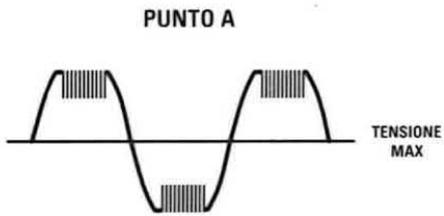
Fig.3 Quando ruotiamo il potenziometro R6 per ottenere in uscita la massima tensione, sul "punto A" di TRC1 rileviamo delle semionde quasi quadrate con una serie d'impulsi generati dal diodo Diac. Il triac TRC2 s'innescia sul primo impulso a sinistra di ogni semionda.
