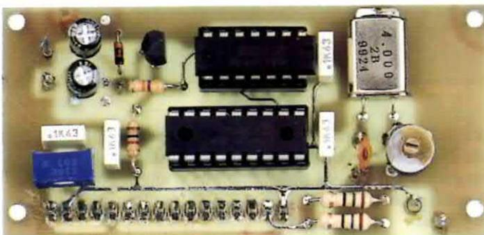
Fig.8 Foto del circuito LX.1543 con sopra montati tutti i componenti. Facciamo presente che questo frequenzimetro riesce a leggere una frequenza max di circa 700.000 Hz.
