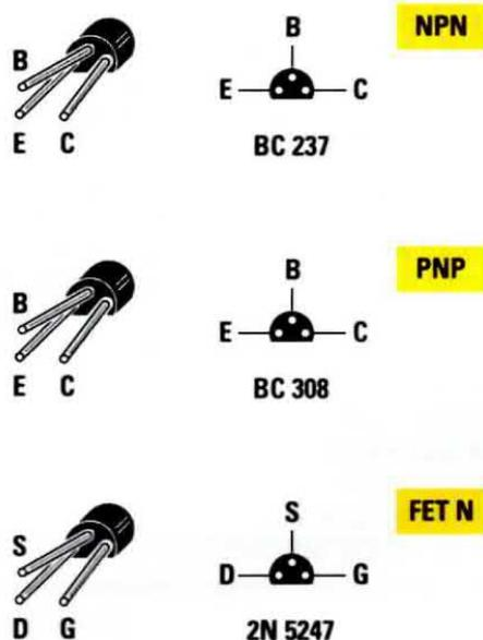
**Fig.39** Per testare il Tracciacurve abbiamo incluso nel kit un transistor NPN siglato BC.237, un transistor PNP siglato BC.308 e un Fet siglato 2N.5247. Nel disegno le connessioni E-B-C dei Transistor e quelle D-S-G del Fet.
