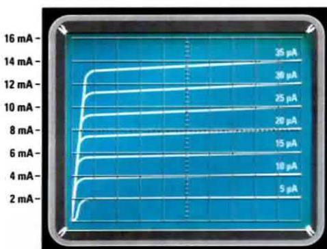
Fig.44 Se avete ruotato il commutatore VOLTS/DIV. del CH2 per una sensibilità media, ad esempio a 0,2 volt, sullo schermo vedrete 7 tracce complete e uniformemente ben distribuite.
