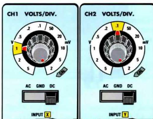
Fig.33 Terminata la taratura del **tracciacurve**, per predisporre l'oscilloscopio alle misure dovete ruotare la manopola del **VOLTS/DIV.** del **CH1** su **1 volt** e quella del **CH2** su **0.1 volt**. I selettori d'ingresso devono essere entrambi posizionati su **DC**.
