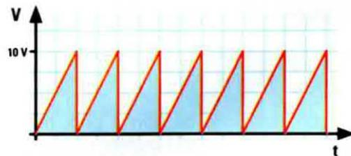
Fig.15 Collegando l'oscilloscopio alla boccia C (collettore), presente sul pannello frontale del Tracciacurve, dobbiamo ruotare il cursore del trimmer **R20** fino a vedere una **rampa a dente di sega** la cui ampiezza raggiunga esattamente i **10 volt** di picco.
