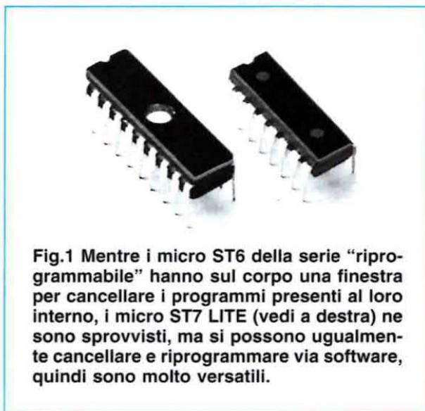
**Fig.1** Mentre i micro ST6 della serie "riprogrammabile" hanno sul corpo una finestra per cancellare i programmi presenti al loro interno, i micro ST7 LITE (vedi a destra) ne sono sprovvisti, ma si possono ugualmente cancellare e riprogrammare via software, quindi sono molto versatili.
