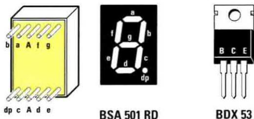
Fig.7 Connessioni viste da dietro del display a 7 segmenti utilizzato in questo progetto. I terminali con la A maiuscola vanno collegati alla tensione positiva dei 5 volt (vedi fig.6).
