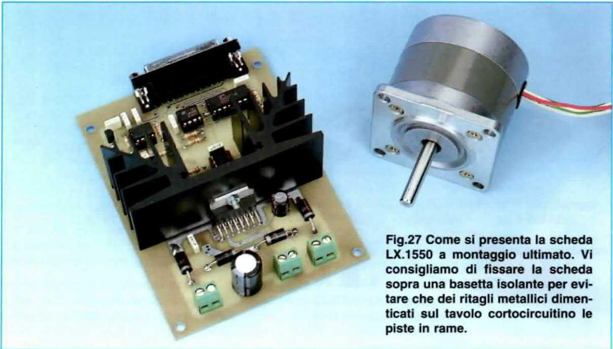
**Fig.27** Come si presenta la scheda LX.1550 a montaggio ultimato. Vi consigliamo di fissare la scheda sopra una basetta isolante per evitare che dei ritagli metallici dimenticati sul tavolo cortocircuitino le piste in rame.
