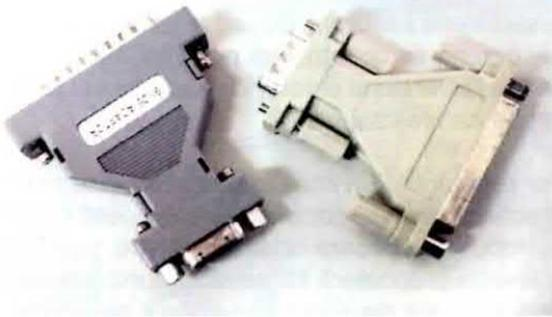
Fig.18 Se nel vostro computer l'uscita RS.232 è a 9 poli anziché a 25 poli, dovete procurarvi un comune adattatore che potete trovare in un qualsiasi negozio di PC.
