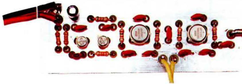
Fig.10 Il piccolo circuito stampato siglato CS.1552 è un doppia faccia con i fori metallizzati. Lo strato di rame prestagnato, visibile sulla parte superiore del circuito, serve da schermo per le piste presenti sulla superficie inferiore. Sul circuito stampato che invieremo assieme al kit, troverete riportato un disegno serigrafico completo di sigle dei singoli componenti e della vernice antiossidante depositata su entrambi i lati.
