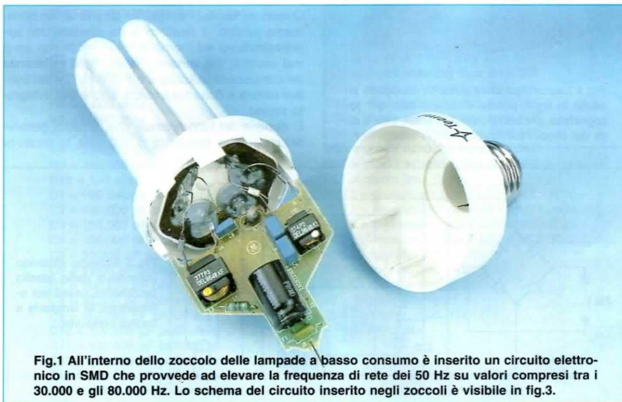
**Fig.1** All'interno dello zoccolo delle lampade a basso consumo è inserito un circuito elettronico in SMD che provvede ad elevare la frequenza di rete dei 50 Hz su valori compresi tra i 30.000 e gli 80.000 Hz. Lo schema del circuito inserito negli zoccoli è visibile in fig.3.
