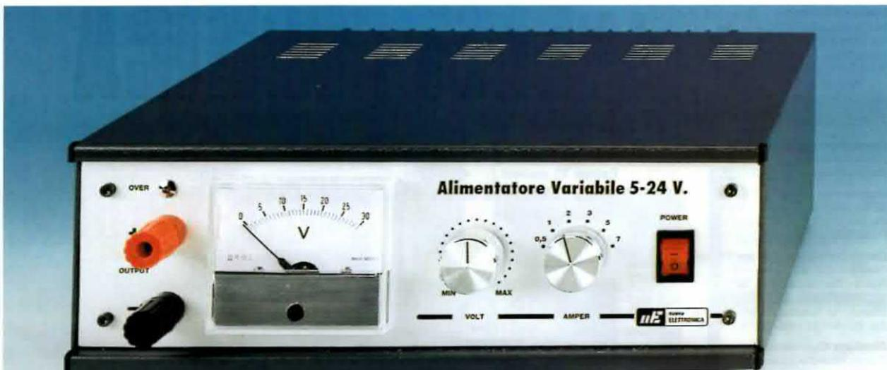
Fig.1 Come si presenta il mobile dell'alimentatore stabilizzato descritto nell'articolo.
