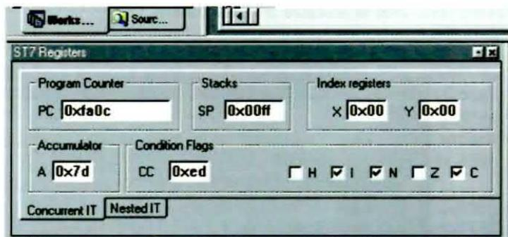
**Fig.6** Quando avrete ingrandito la finestra ST7 Registers, potrete controllare in tempo reale il contenuto dei registri di sistema. Il prefisso 0x indica che i valori sono in esadecimale.
