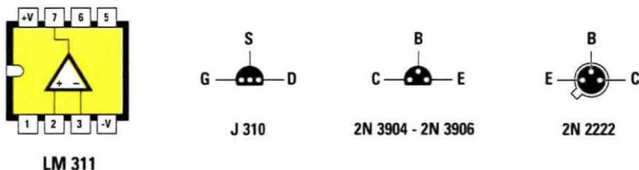
Fig.2 Connessioni dell'integrato LM.311 viste da sopra e con la tacca di riferimento a U rivolta verso sinistra e connessioni viste da sotto del fet J310, dei transistors 2N3904-2N3906 e 2N2222 utilizzati in questo circuito.
