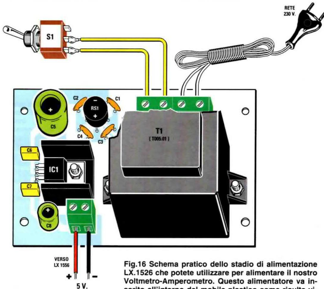
Fig.16 Schema pratico dello stadio di alimentazione LX.1526 che potete utilizzare per alimentare il nostro Voltmetro-Amperometro. Questo alimentatore va inserito all'interno del mobile plastico come risulta visibile anche nella foto di fig.14.
