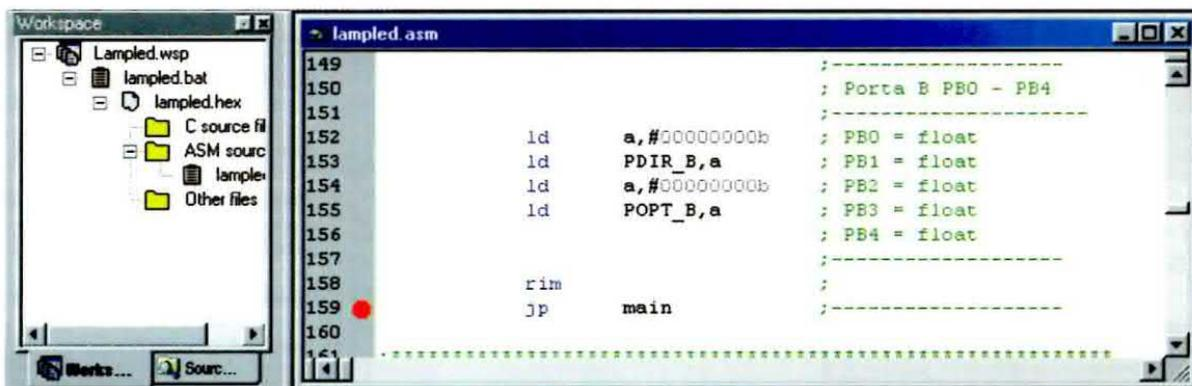
**Fig.15** Aiutandovi con la barra di scorrimento verticale, che si trova sull’estrema destra della finestra `lamped.asm`, cercate la riga 159, quindi cliccando sempre sulla zona grigia con il tasto sinistro del mouse, attivate il secondo breakpoint.
