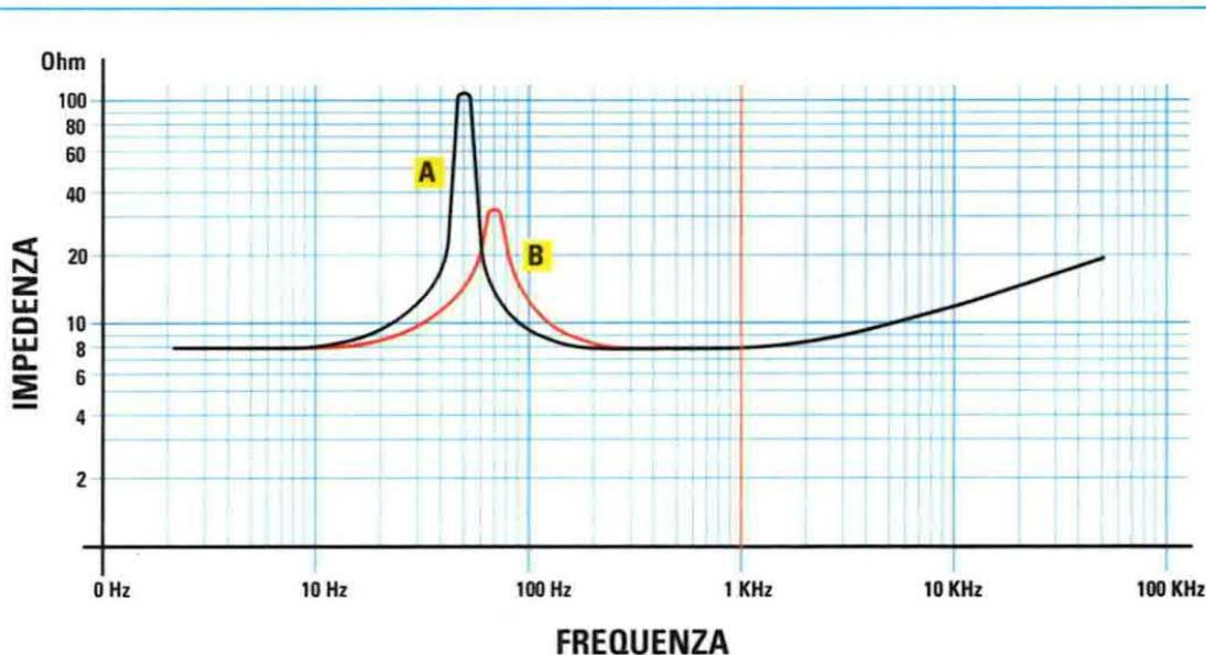
Fig.1 L'aria esercita sul cono dell'altoparlante una forza che ad una determinata frequenza genera una "risonanza meccanica". Il picco "A" visibile in questo disegno è il valore della "frequenza di risonanza" di un altoparlante in aria libera, mentre il picco "B" è la "frequenza di risonanza" dello stesso altoparlante racchiuso entro una Cassa Acustica. In "A" abbiamo un valore d'impedenza di 100 ohm ad una frequenza di circa 50 Hz, mentre in "B" un valore d'impedenza di 40 ohm a circa 70 Hz.
