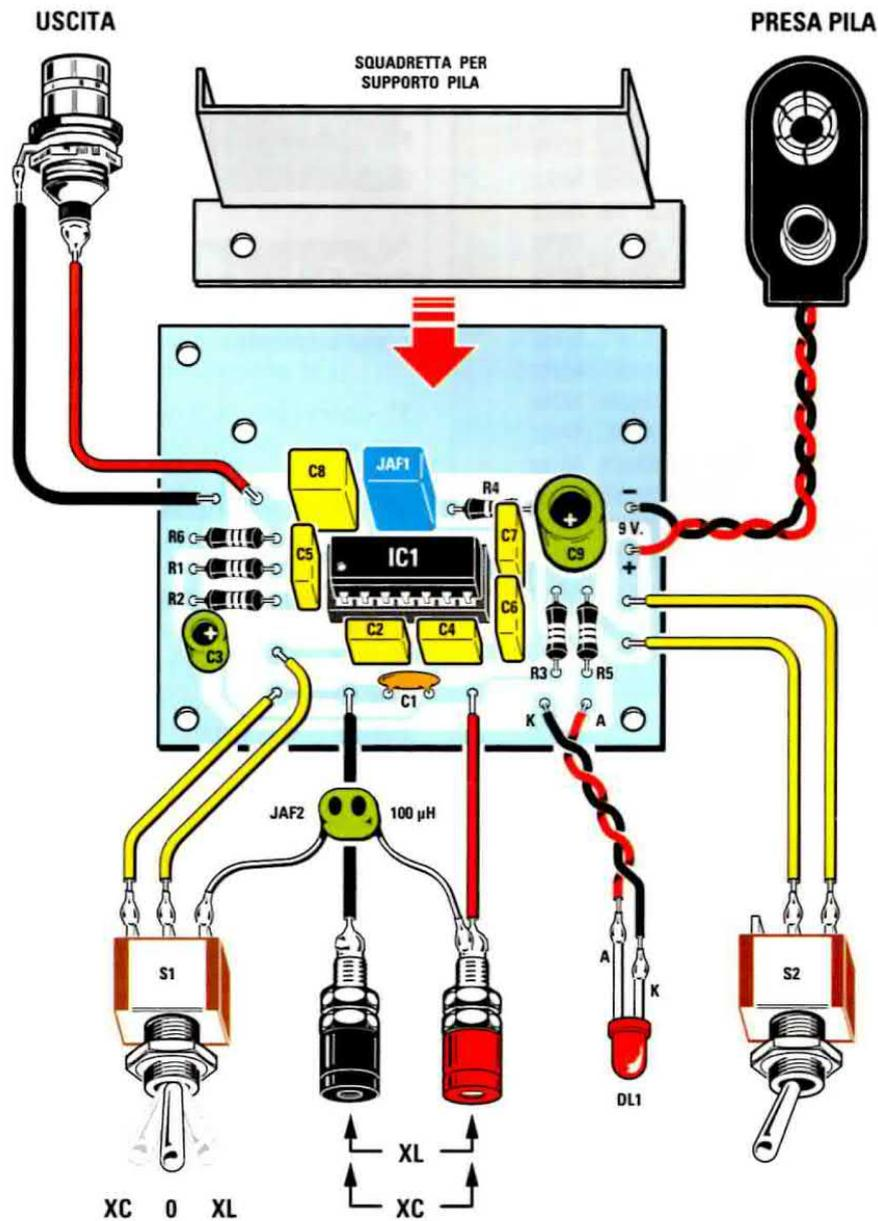
Fig.3 Per il montaggio di questo kit consigliamo di seguire le istruzioni riportate nella rivista N.212 collegando l'impedenza JAF2, da 100 microhenry, al terminale del deviatore S1 come visibile in figura. Per leggere la frequenza generata basta collegare un qualsiasi frequenzimetro digitale al bocchettone d'uscita BNC.
