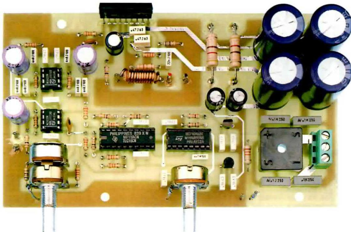
**Fig.8** Come si presenta il circuito dell'amplificatore Sub-Woofer una volta montati tutti i suoi componenti. I potenziometri R8-R10 ed R5 vanno direttamente saldati sul circuito stampato dopo aver accorciato i loro perni come visibile in fig.15.
