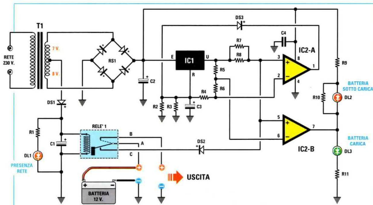
**Fig.2** Schema elettrico del circuito per Black-Out. Nel preciso istante in cui viene a mancare la corrente elettrica, il relè si diseccita e i 12 volt della batteria giungono sulle bocche d'uscita e da qui prelevati per accendere una lampadina o per far suonare una cicalina.
