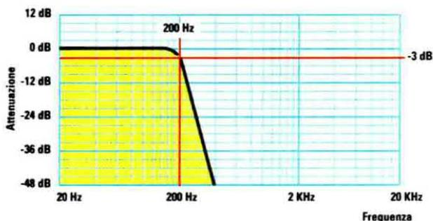
**Fig.4** Un solo filtro passa-basso contenuto nell'integrato **MF.10** (vedi fig.6) è in grado di attenuare un segnale di ben **12 dB x ottava**. Poiché noi ne colleghiamo due in serie, otterremo una attenuazione di ben **24 dB x ottava**.
