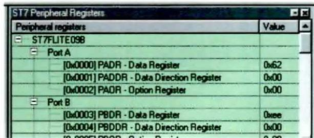
Fig.9 Cliccando su ogni quadratino accanto alle scritte Port A, Port B, ecc., aprirte un elenco dei registri usati da ogni periferica e da ogni funzione aggiuntiva del microprocessore.
