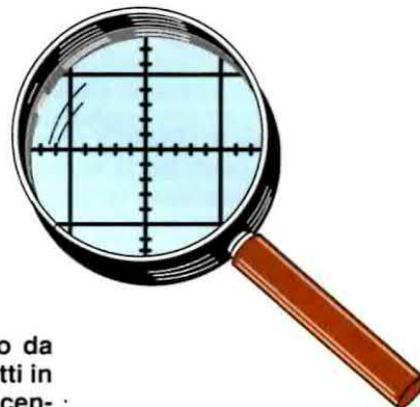
Fig.2 Lo schermo dell'oscilloscopio è composto da un rettangolo quadrettato suddiviso in 10 quadretti in orizzontale e 8 quadretti in verticale. Sulla parte centrale dello schermo è presente una "croce" che divide il lato di ciascun quadretto in "5 parti" che, come vi spiegheremo, risulteranno molto utili per effettuare delle misure di precisione.
