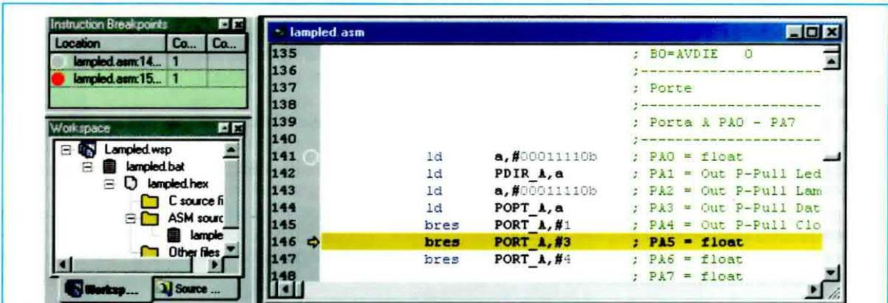
**Fig.23** Per disattivare un breakpoint senza eliminarlo totalmente, posizionatevi, aiutandovi con la barra di scorrimento verticale, alla riga in cui è stato attivato il breakpoint, quindi cliccate sul cerchietto rosso e quest'ultimo diventerà grigio con bordo bianco.
