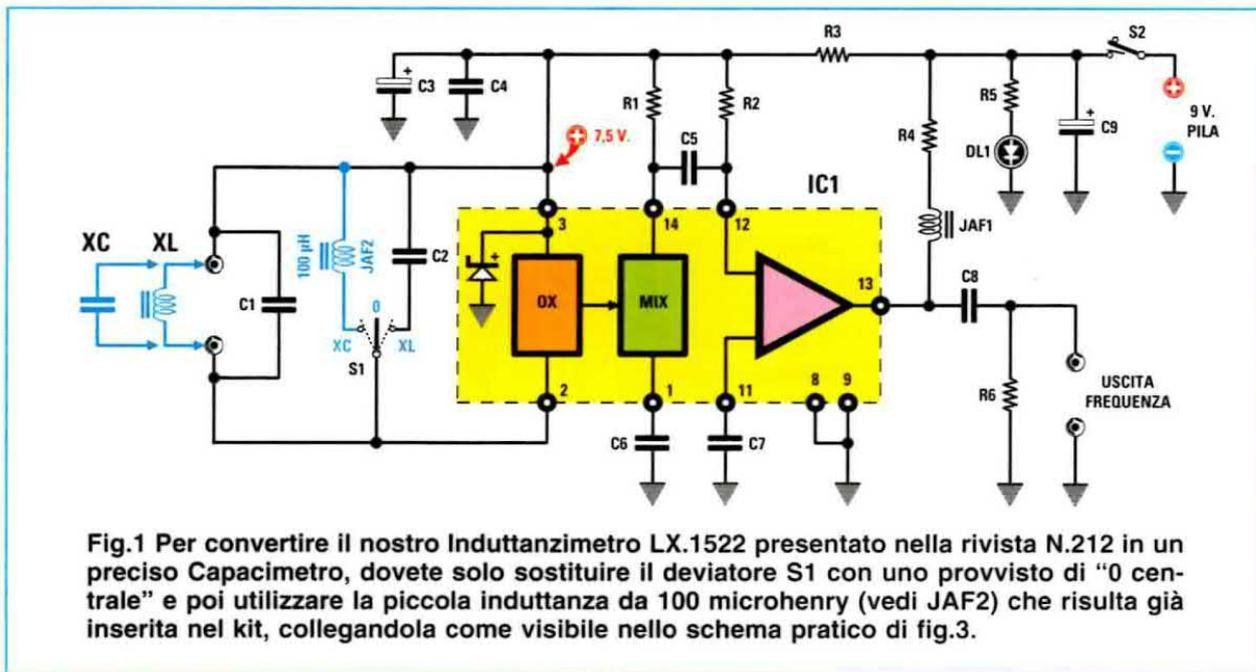
Fig.1 Per convertire il nostro Induttanzimetro LX.1522 presentato nella rivista N.212 in un preciso Capacimetro, dovete solo sostituire il deviatore S1 con uno provvisto di "0 centrale" e poi utilizzare la piccola induttanza da 100 microhenry (vedi JAF2) che risulta già inserita nel kit, collegandola come visibile nello schema pratico di fig.3.
