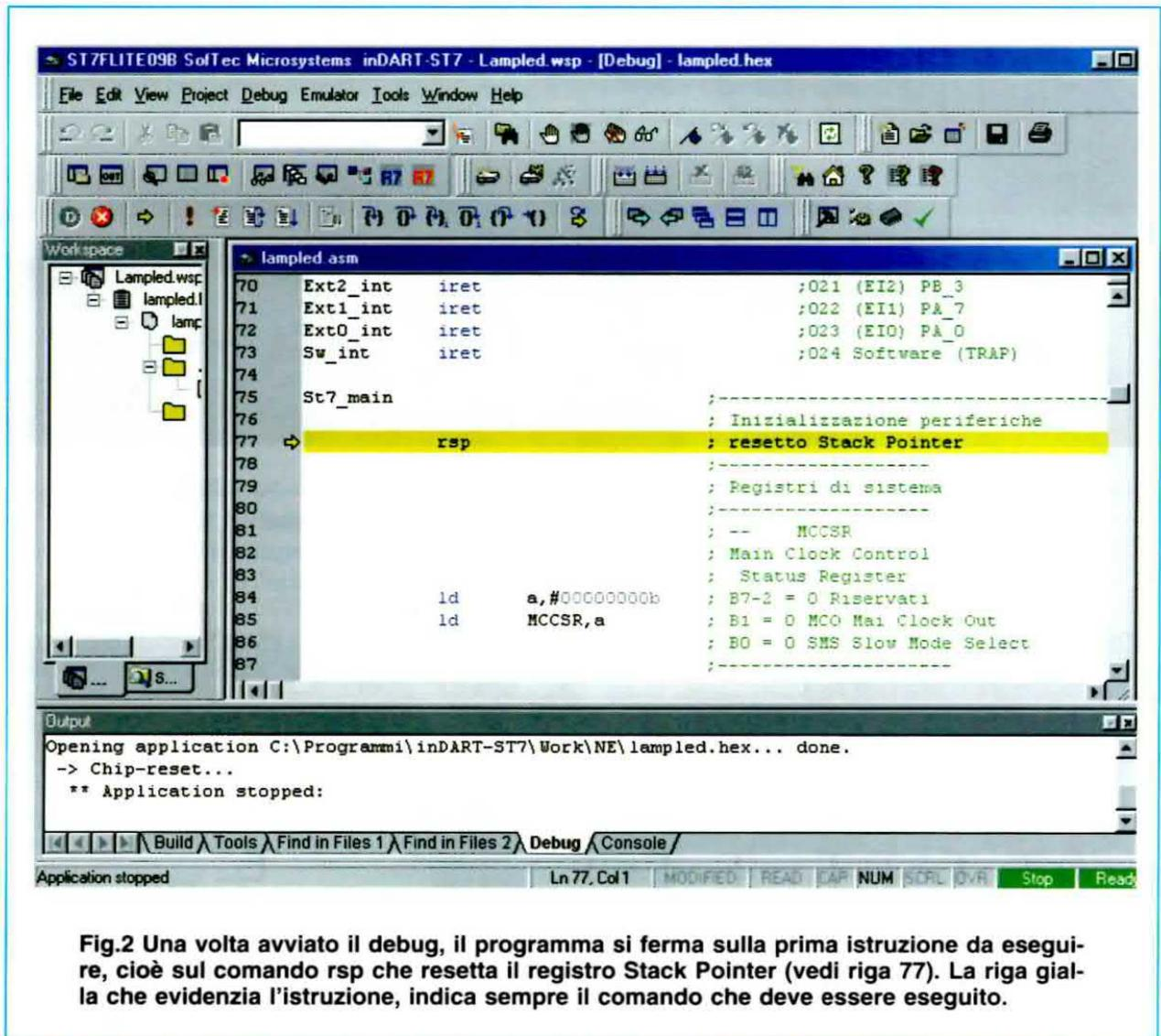
**Fig.2** Una volta avviato il debug, il programma si ferma sulla prima istruzione da eseguire, cioè sul comando **rsp** che resetta il registro Stack Pointer (vedi riga 77). La riga gialla che evidenzia l'istruzione, indica sempre il comando che deve essere eseguito.
