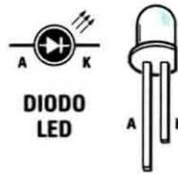
Fig.3 Ricordate che il terminale più lungo di un diodo è l'Anodo e il più corto è il Catodo.
