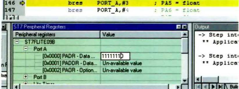
Fig.21 Cambiando il valore da 0 a 1 del registro PADR e premendo Invio, il led DL1 si spegne.
