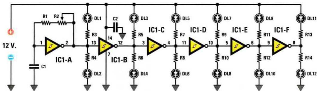
Fig.3 Schema elettrico del circuito che, utilizzando un solo integrato C/Mos, è in grado di far lampeggiare ben 12 diodi led. Il trimmer R2, collegato al primo inverters siglato IC1/A, viene utilizzato per variare la velocità del lampeggio.
