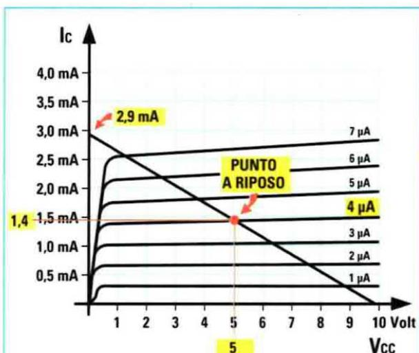
Fig.2 Per ricavare il "punto a riposo" di un transistor tracciate la sua retta di carico, poi sul valore  $V_{cc} : 2$  tracciate una linea verticale fino ad incontrare la 4° traccia: tracciando da questo punto una linea orizzontale verso sinistra potrete conoscere la corrente di Collettore.
