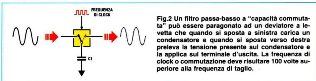
Fig.2 Un filtro passa-basso a "capacità commutata" può essere paragonato ad un deviatore a levetta che quando si sposta a sinistra carica un condensatore e quando si sposta verso destra preleva la tensione presente sul condensatore e la applica sul terminale d'uscita. La frequenza di clock o commutazione deve risultare 100 volte superiore alla frequenza di taglio.
