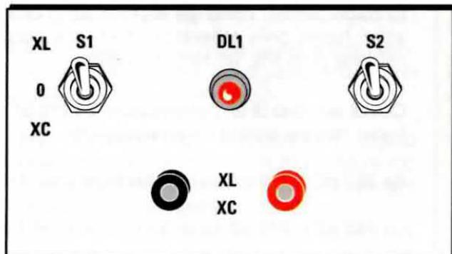
Fig.4 Sul pannello frontale del mobile dovete solo riportare la sigla XC quando il deviatore S1 collega l'impedenza JAF2 da 100 microhenry ai terminali 3-2 dello stadio oscillatore IC1 (vedi fig.1) e la sigla XL quando invece collega il condensatore C2.
