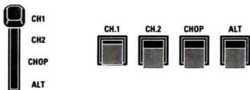
Fig.14 I tasti CH.1-CH.2-CHOP-ALT che in fig.9 abbiamo posto in verticale tra i due selettori d'ingresso CH1-CH2, in alcuni oscilloscopi possono essere posizionati in senso orizzontale oppure sostituiti da un solo selettore a slitta.
