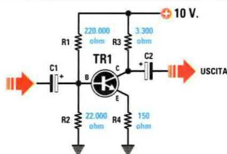
Fig.1 Schema elettrico del preamplificatore preso come esempio per calcolare i valori delle resistenze di polarizzazione utilizzando una tensione Vcc di 10 volt.
