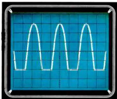
**Fig.7** Applicando sulla Base del transistor che presenta il punto di riposo spostato sui 3,8 volt come visibile in fig.4, un segnale la cui ampiezza supera il massimo valore consentito, il segnale amplificato che uscirà dal suo Collettore risulterà tosato solo sulle semionde negative. Per risolvere questo problema è sempre consigliabile ricalcolare il guadagno del transistor per un valore minore.
