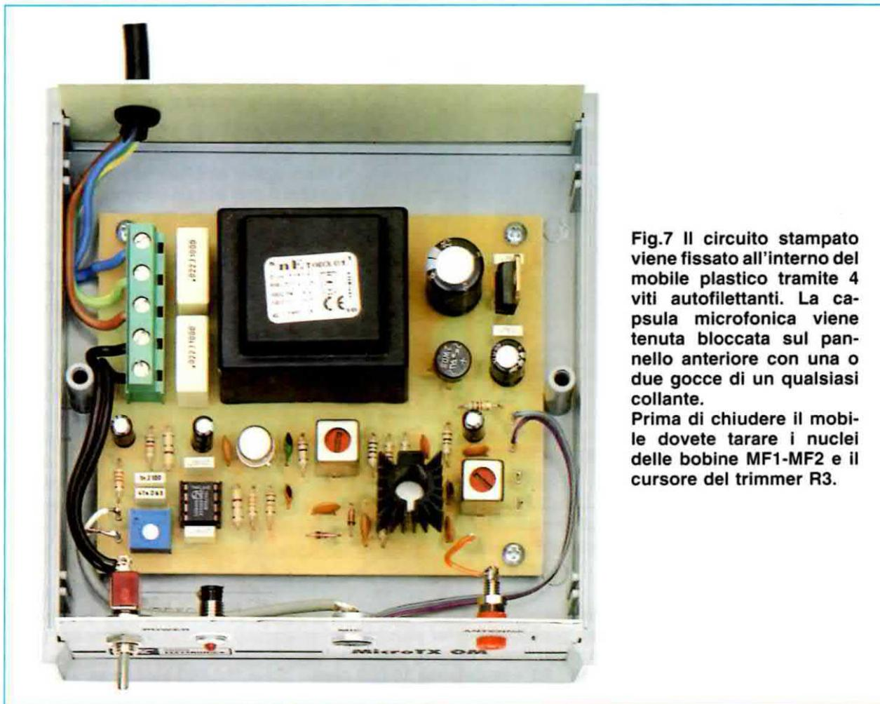
**Fig.7** Il circuito stampato viene fissato all'interno del mobile plastico tramite 4 viti autofilettanti. La capsula microfonica viene tenuta bloccata sul pannello anteriore con una o due gocce di un qualsiasi collante. Prima di chiudere il mobile dovete tarare i nuclei delle bobine MF1-MF2 e il cursore del trimmer R3.
