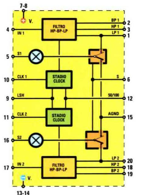
Fig.6 Schema a blocchi e connessioni viste da sopra del filtro MF.10.
