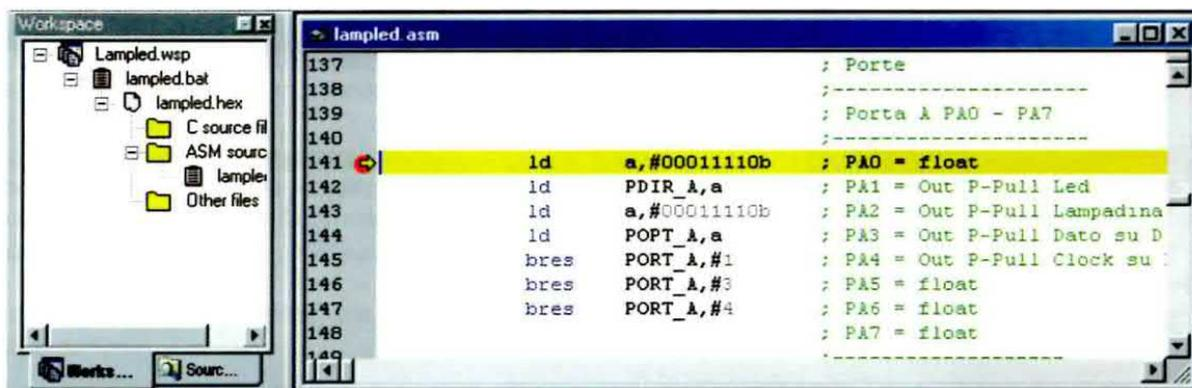
**Fig.14** Per inserire un breakpoint, cioè un “punto di interruzione” nell’esecuzione, cliccate col tasto sinistro sulla zona grigia della riga corrispondente all’istruzione sulla quale volete bloccare l’esecuzione. Il cerchio rosso segnala l’attivazione del breakpoint.
