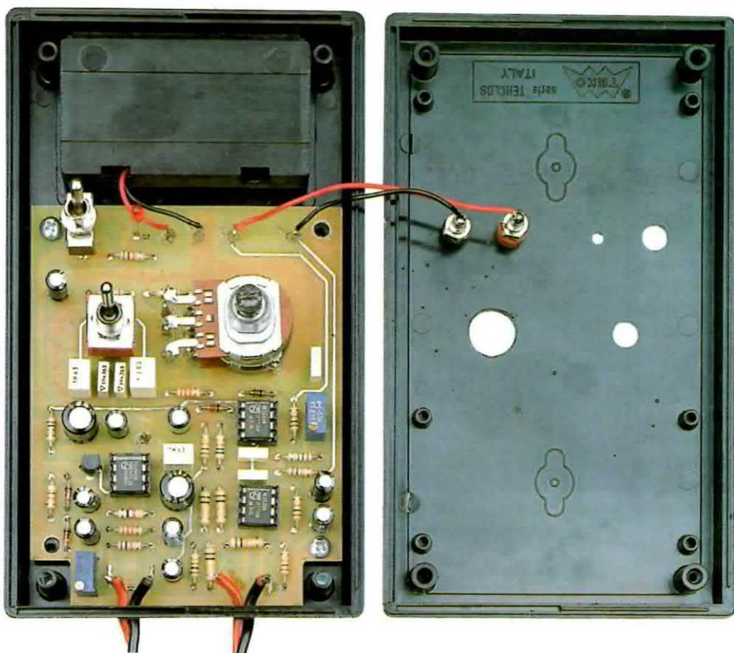
Fig.9 La basetta del circuito stampato verrà fissata nel semicoperchio del mobiletto plastico dove risulta presente il vano della pila da 9 volt. Nell'opposto semicoperchio verranno fissate le due boccole per il tester (vedi fig.10).
