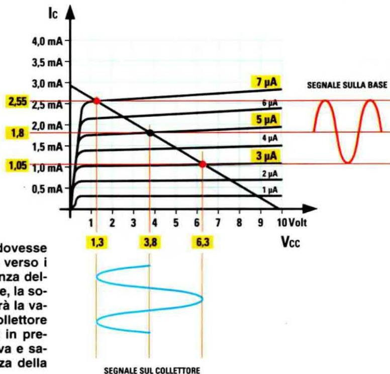
Fig.4 Se il punto a riposo dovesse spostarsi dai richiesti 5 volt verso 3,8 volt a causa della tolleranza delle resistenze di polarizzazione, la sola differenza che noterete sarà la variazione della tensione di Collettore che scenderà verso 1,3 volt in presenza della semionda positiva e salirà verso 6,3 volt in presenza della semionda negativa. Come potrete notare, il segnale amplificato non viene distorto.
