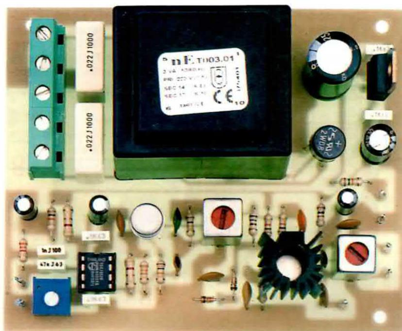
Fig.6 Foto del circuito stampato del TX per Onde Medie con sopra già montati tutti i suoi componenti. Nel corpo del transistor TR2 va inserita l'aletta di raffreddamento che vi forniamo assieme al kit.
