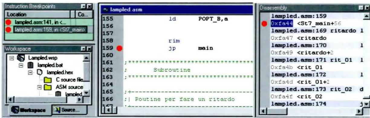
Fig.17 Cliccando due volte con il tasto sinistro del mouse sulla seconda riga della finestra Instruction Breakpoints, nella finestra lamped.asm viene visualizzata la riga 159 alla quale è associato il breakpoint, senza che venga eseguita alcuna istruzione.
