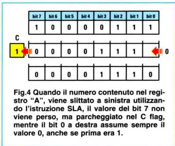
Fig.4 Quando il numero contenuto nel registro “A”, viene slittato a sinistra utilizzando l’istruzione **SLA**, il valore del bit 7 non viene perso, ma parcheggiato nel **C flag**, mentre il bit 0 a destra assume sempre il valore 0, anche se prima era 1.
