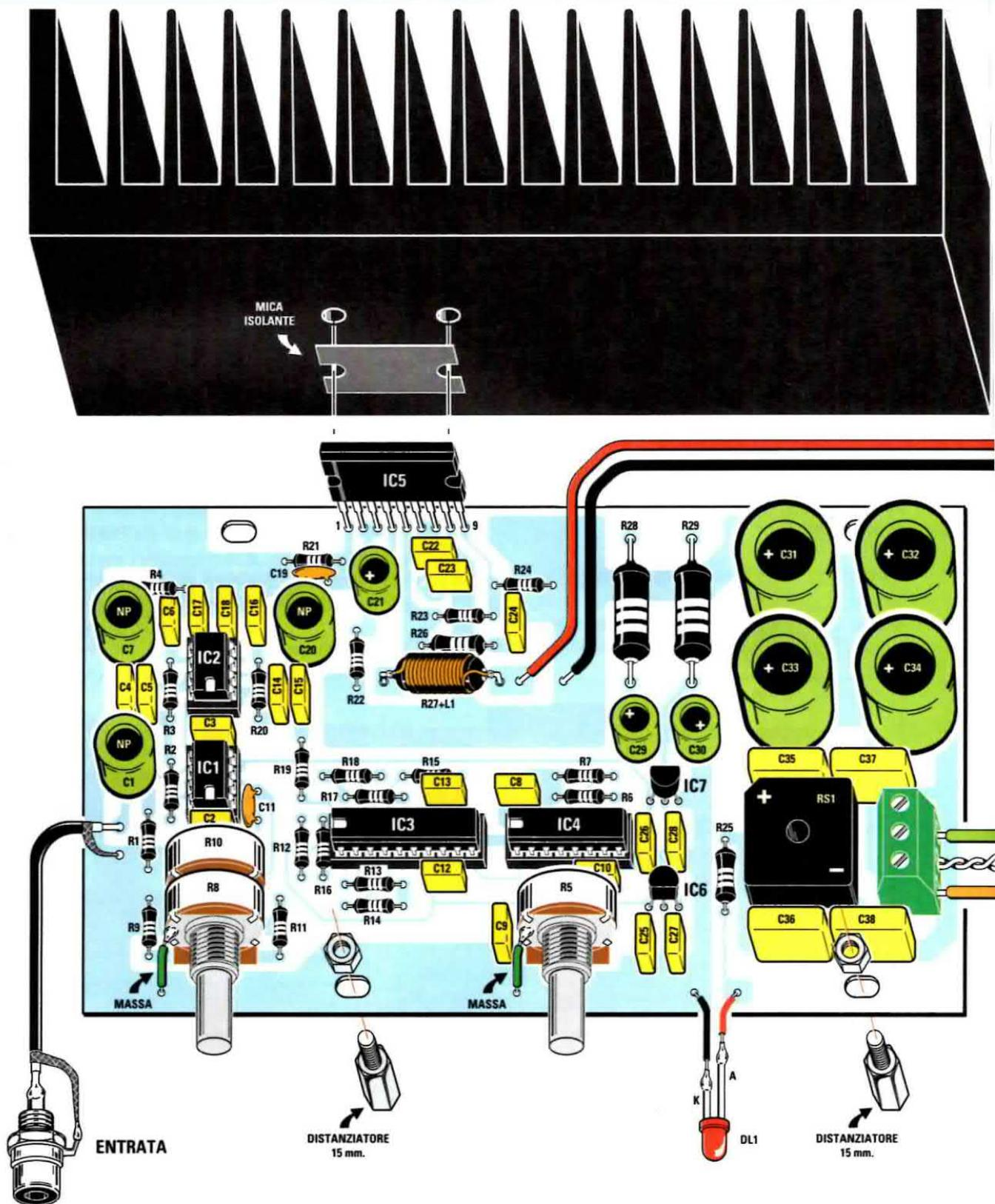
Fig.9 Schema pratico di montaggio. Prima di fissare il corpo dell'integrato TDA.1514/A sull'aletta di raffreddamento, non dimenticate di inserire la "mica isolante" rettangolare che troverete nel kit. Dei 4 fili che escono dal trasformatore T1, i due "centrali" vanno collegati al foro centrale della morsettieria posta vicino al ponte raddrizzatore RS1.
