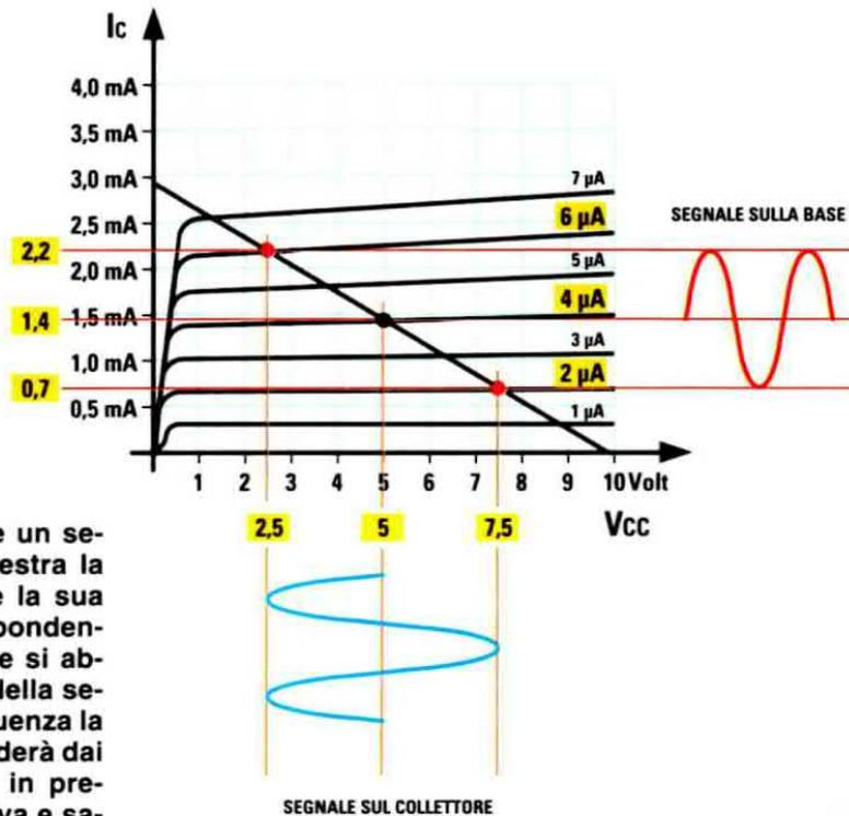
Fig.3 Applicando sulla Base un segnale sinusoidale (vedi a destra la sinusoide blu) noterete che la sua corrente si alzerà in corrispondenza della semionda positiva e si abbasserà in corrispondenza della semionda negativa. Di conseguenza la tensione sul Collettore scenderà dai 5 volt di riposo ai 2,5 volt in presenza della semionda positiva e salirà a 7,5 volt in presenza della semionda negativa.
