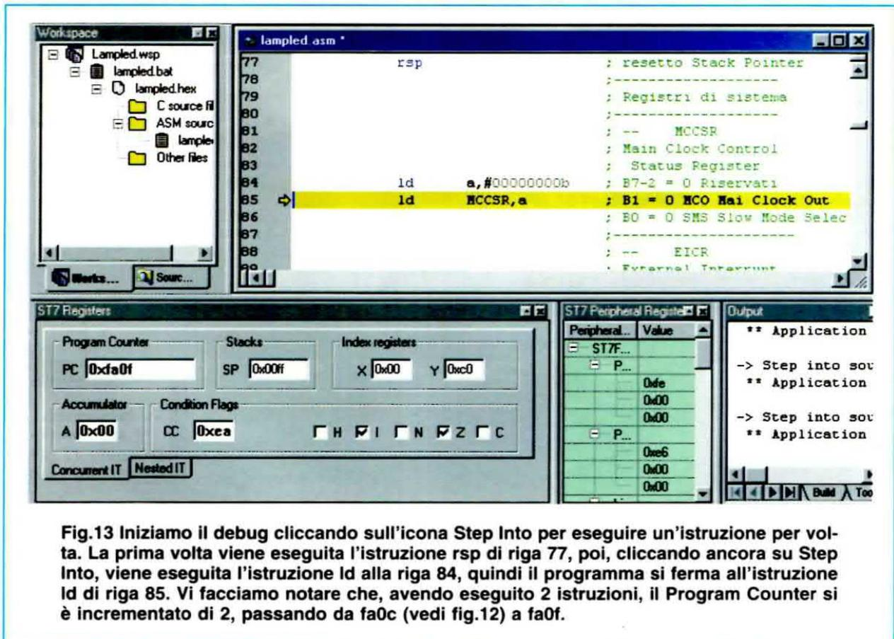
**Fig.13** Iniziamo il debug cliccando sull'icona Step Into per eseguire un'istruzione per volta. La prima volta viene eseguita l'istruzione **rsp** di riga 77, poi, cliccando ancora su Step Into, viene eseguita l'istruzione **ld** alla riga 84, quindi il programma si ferma all'istruzione **ld** di riga 85. Vi facciamo notare che, avendo eseguito 2 istruzioni, il Program Counter si è incrementato di 2, passando da **fa0c** (vedi fig.12) a **fa0f**.
