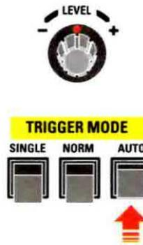
Fig.24 Per bloccare in automatico la traccia di un segnale occorre premere il pulsante AUTO del TRIGGER MODE. Se la traccia non rimane ferma allora si può agire sulla piccola manopola di LEVEL, ruotandola verso il + o verso il - fino a bloccare l'immagine sullo schermo.
