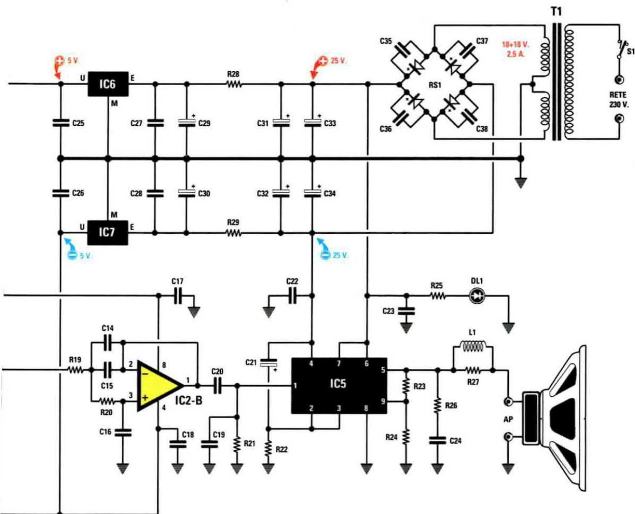
Se si utilizza un altoparlante da 8 ohm, si ottiene in uscita una potenza RMS di 25 watt pari a 50 watt musicali, mentre se si utilizza un altoparlante da 4 ohm, si ottiene in uscita una potenza RMS di 40 watt pari ad una potenza musicale di 80 watt.
