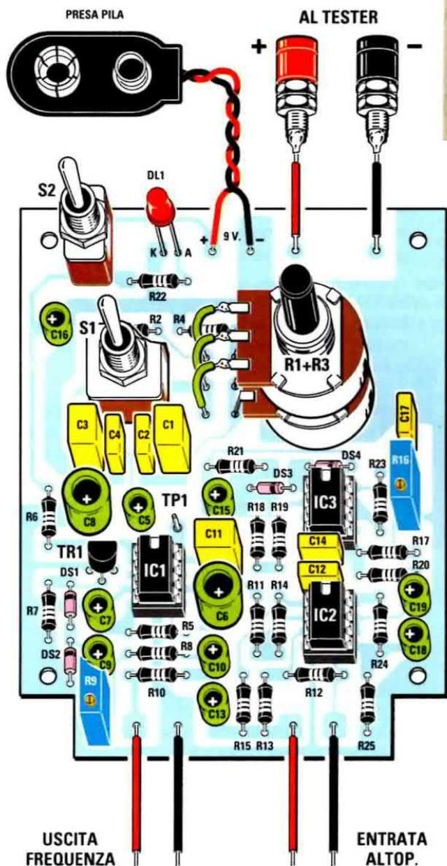
Fig.8 Schema pratico di montaggio del circuito idoneo a misurare l'impedenza di un qualsiasi altoparlante o cuffia.
