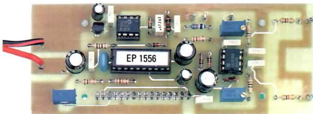
**Fig.13** Foto del circuito già montato e pronto per l'uso. Questo Voltmetro - Amperometro può essere inserito all'interno di un qualsiasi Alimentatore Stabilizzato, purchè si riesca a prelevare dallo stesso una tensione stabilizzata di 5 volt per poterlo alimentare, diversamente si adotterà la soluzione visibile in fig.14.
