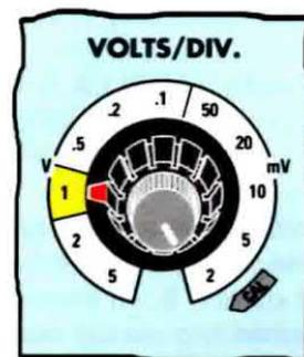
**Fig.10** Il selettore contrassegnato dalla dicitura **VOLTS/DIV.** consente di variare la sensibilità di ingresso dell'amplificatore verticale. Ricordatevi che il "punto" che precede un numero va inteso come "virgola", quindi **.5 - .2** va letto **0,5 - 0,2** volt.
