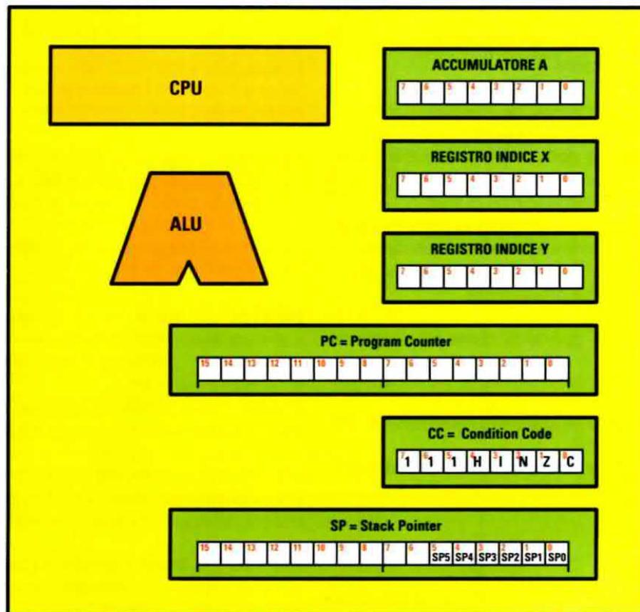
Fig.3 Il "core" del microprocessore ST7 LITE 09 è composto da un'unità di elaborazione centrale chiamata CPU e da una ALU, che gestisce tutte le operazioni aritmetiche e logiche utilizzando anche l'Accumulatore A. Fanno parte del "core" anche i due Registri X e Y, il Program Counter, il Condition Code e lo Stack Pointer. Nel registro Stack Pointer si utilizzano i soli bit da SP0 a SP5.
