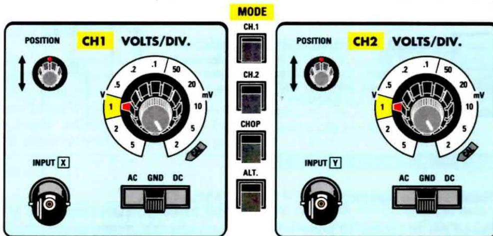
**Fig.9** In ogni oscilloscopio (vedi fig.1) sono sempre presenti due identiche sezioni. L'ingresso di sinistra indicato INPUT X è del canale CH1 e quello di destra indicato INPUT Y è del canale CH2. In entrambi i canali è presente il selettore VOLTS/DIV.
