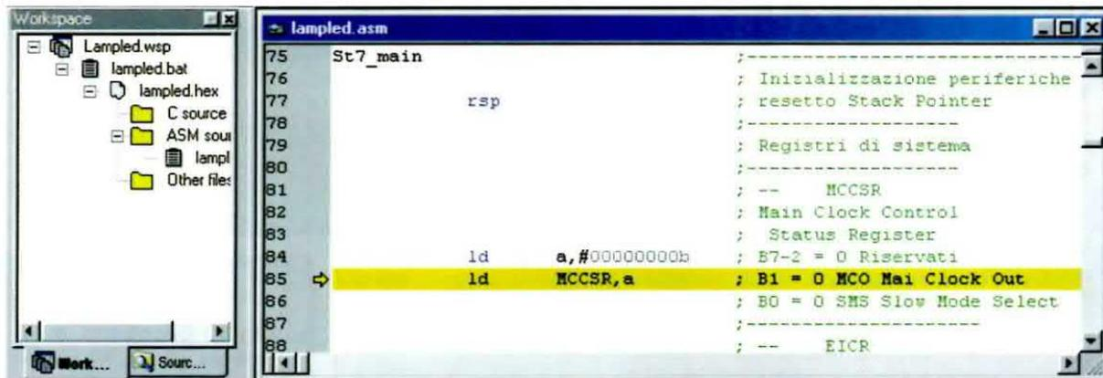
Fig.28 Cliccando una volta sull'icona Chip reset e due volte sull'icona Step Into (vedi fig.1), il debug si ferma sulla riga con l'istruzione ld MCCSR,a. Il registro MCCR permette di gestire la frequenza di clock della CPU tramite il bit 0 siglato SMS (vedi fig.29).
