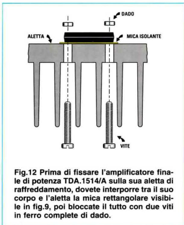
**Fig.12** Prima di fissare l'amplificatore finale di potenza TDA.1514/A sulla sua aletta di raffreddamento, dovete interporre tra il suo corpo e l'aletta la mica rettangolare visibile in fig.9, poi bloccate il tutto con due viti in ferro complete di dado.
