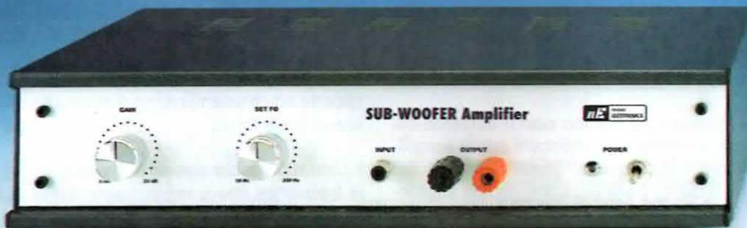
Fig.1 L'amplificatore Sub-Woofer che vi proponiamo in queste pagine va racchiuso dentro un mobile metallico completo di mascherina in alluminio forata e serigrafata.
