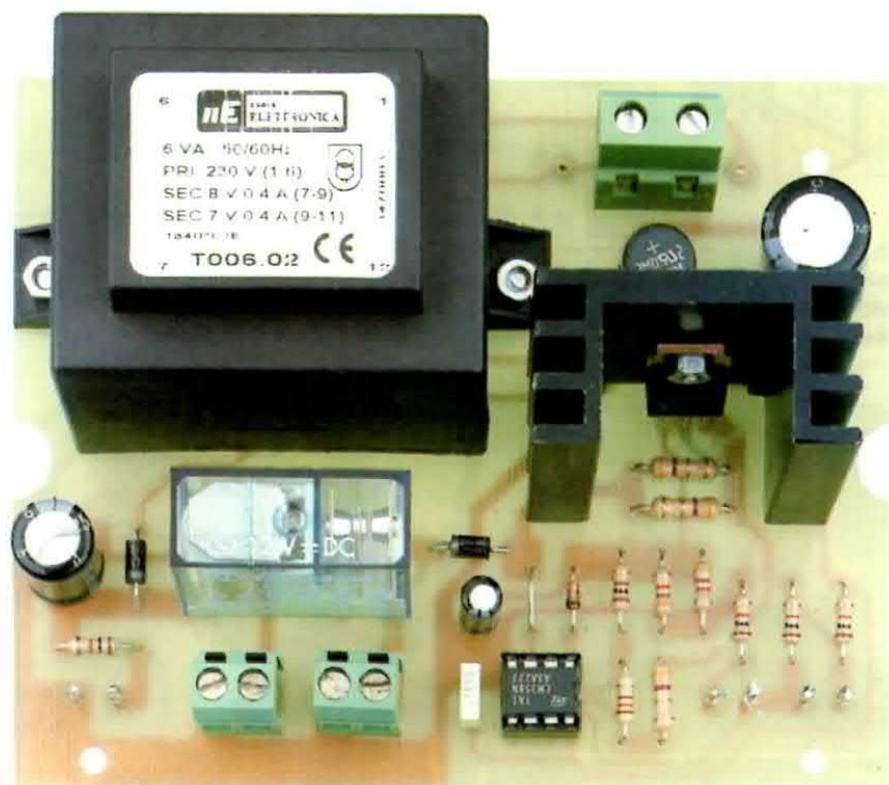
Fig.5 Come si presenta il circuito stampato a montaggio ultimato. In fig.4 potete vedere i rimanenti collegamenti esterni.
