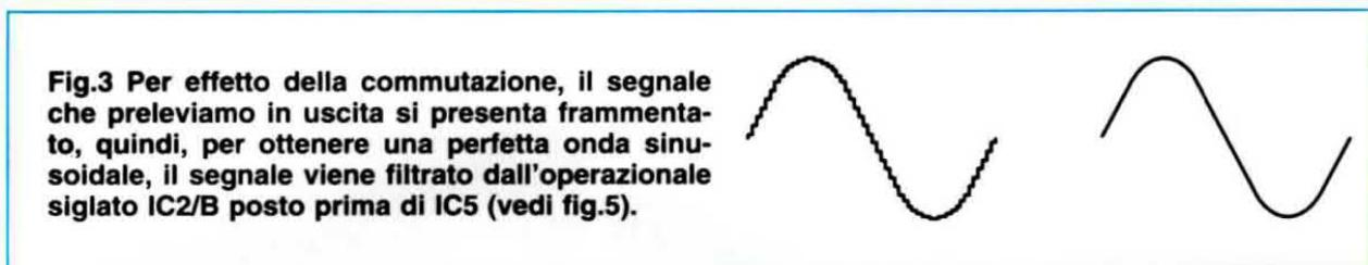
Fig.3 Per effetto della commutazione, il segnale che preleviamo in uscita si presenta frammentato, quindi, per ottenere una perfetta onda sinusoidale, il segnale viene filtrato dall'operazionale siglato IC2/B posto prima di IC5 (vedi fig.5).
