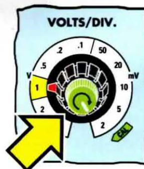
**Fig.11** La piccola manopola posta sul selettore **VOLTS/DIV.** permette di variare, in modo continuo, il valore dei Volt per Divisione. Per evitare errori di lettura controllate sempre che questa piccola manopola risulti ruotata sulla posizione **CAL**.
