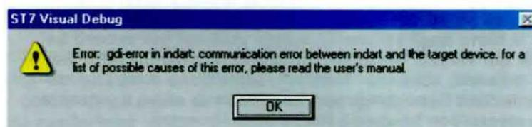
**Fig.3** Quando il micro perde la comunicazione con il computer, compare questo messaggio. In questo caso potete solo cliccare su OK e cominciare di nuovo il debug.
