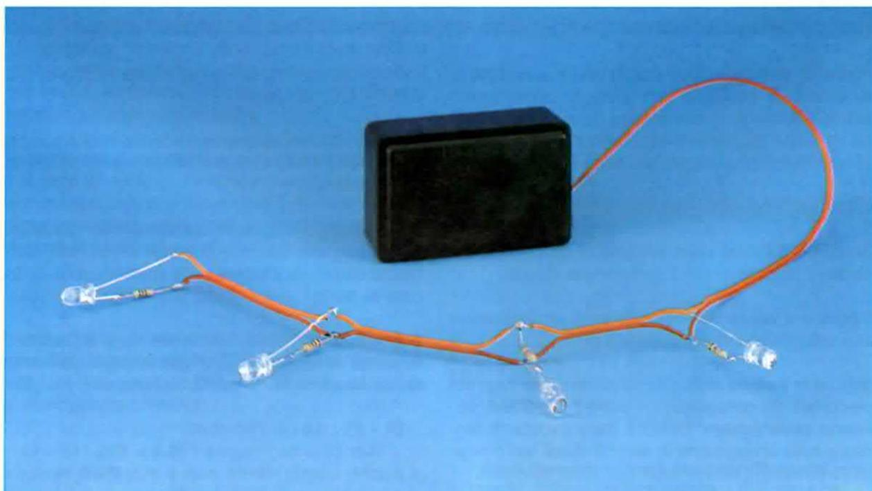
Fig.1 Il corpo dei diodi flash sia di colore Blu che Bianco appare trasparente come il vetro e soltanto all'accensione si può capire di quale dei due tipi si tratta.
