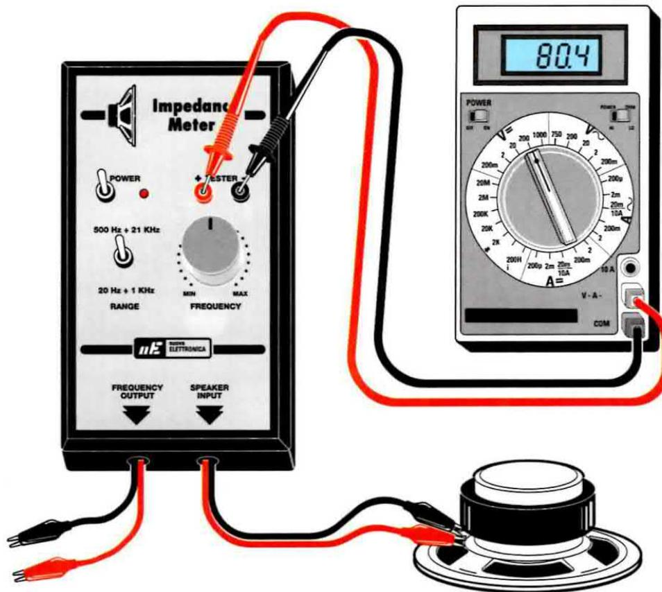
Fig.11 La tensione da applicare al Tester verrà prelevata dalle due bocche poste in alto, utilizzando le sottili banane che alleghiamo al kit. Per misurare l'impedenza di un altoparlante dovete collegare ai suoi terminali i fili che escono dal foro di destra.
