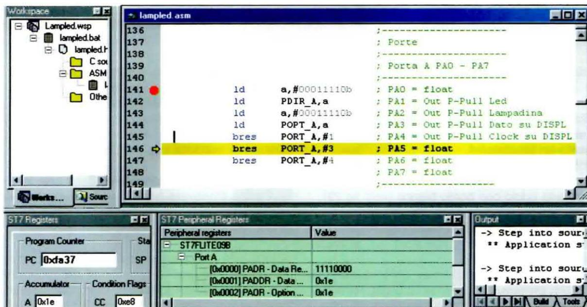
Fig.22 Per modificare il valore del Program Counter così da saltare ad una precisa istruzione alterando la sequenza logica di esecuzione e senza eseguire istruzioni intermedie, cliccate su un punto che non sia la zona grigia della riga alla quale volete saltare e, quando compare una barretta lampeggiante, cliccate sull'icona Set PC (vedi fig.1).
