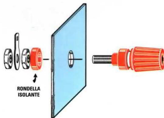
Fig.16 Ricordatevi che prima di fissare al pannello frontale le morsettiere d'uscita, dovrete sfilare dal loro corpo la rondella isolante di plastica che poi inserirete sul retro del pannello in modo da isolarle.
