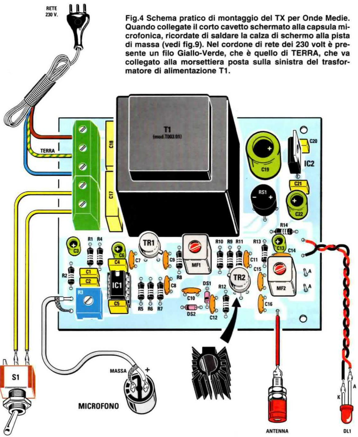
Fig.4 Schema pratico di montaggio del TX per Onde Medie. Quando collegate il corto cavetto schermato alla capsula microfonica, ricordate di saldare la calza di schermo alla pista di massa (vedi fig.9). Nel cordone di rete dei 230 volt è presente un filo Giallo-Verde, che è quello di TERRA, che va collegato alla morsetteria posta sulla sinistra del trasformatore di alimentazione T1.
