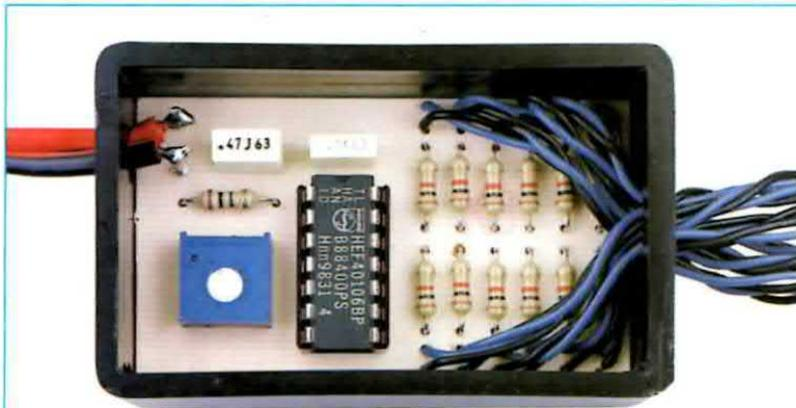
Fig.1 Il circuito va inserito dentro un piccolo contenitore plastico che vi forniamo insieme al kit. Da questo contenitore escono i fili per alimentare tutti i diodi led, come visibile in fig.5.
