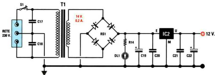
Fig.3 Schema elettrico dello stadio di alimentazione. Si noti il filo di "massa" collegato alla presa centrale della spina di rete dei 230 volt.
