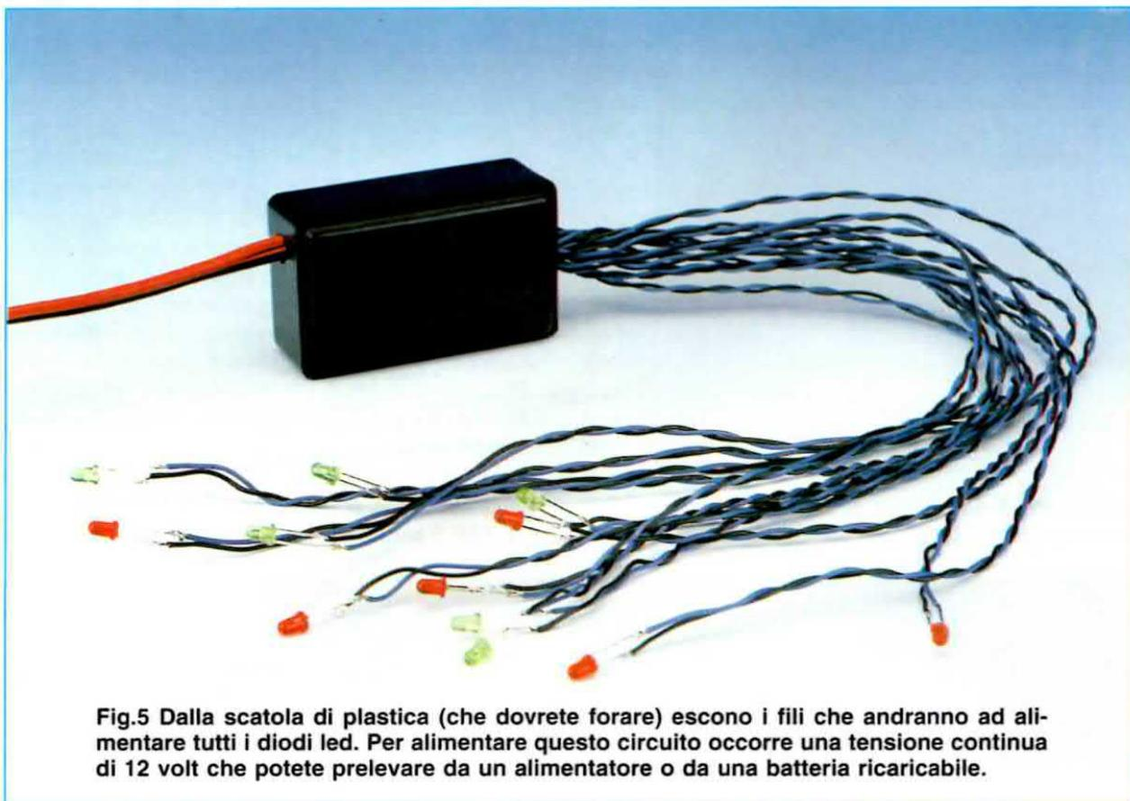
**Fig.5** Dalla scatola di plastica (che dovreste forare) escono i fili che andranno ad alimentare tutti i diodi led. Per alimentare questo circuito occorre una tensione continua di 12 volt che potete prelevare da un alimentatore o da una batteria ricaricabile.
