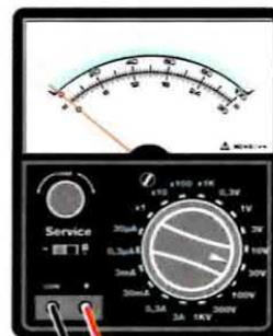
Fig.11 Se non disponete di un oscilloscopio da collegare ai terminali A-A della MF2 (vedi figg.2-5), potete utilizzare un qualsiasi Tester purchè realiziate questa semplice sonda. Il nucleo della MF2 andrà ruotato fino a leggere una tensione di circa 8 volt CC. DS1 = diodo al silicio 1N4148 R1 = resistenza 10.000 ohm C1 = 100.000 picofarad.
