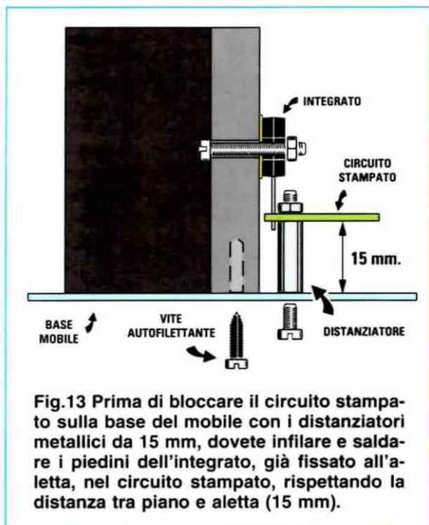
**Fig.13** Prima di bloccare il circuito stampato sulla base del mobile con i distanziatori metallici da 15 mm, dovete infilare e saldare i piedini dell'integrato, già fissato all'aletta, nel circuito stampato, rispettando la distanza tra piano e aletta (15 mm).
