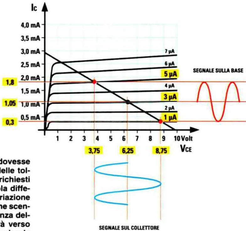
Fig.5 Se il punto a riposo dovesse spostarsi, sempre a causa delle tolleranze delle resistenze, dai richiesti 5 volt verso i 6,25 volt, la sola differenza che noterete sarà la variazione della tensione di Collettore che scenderà verso 3,75 volt in presenza della semionda positiva e salirà verso 8,75 volt in presenza della semionda negativa.
