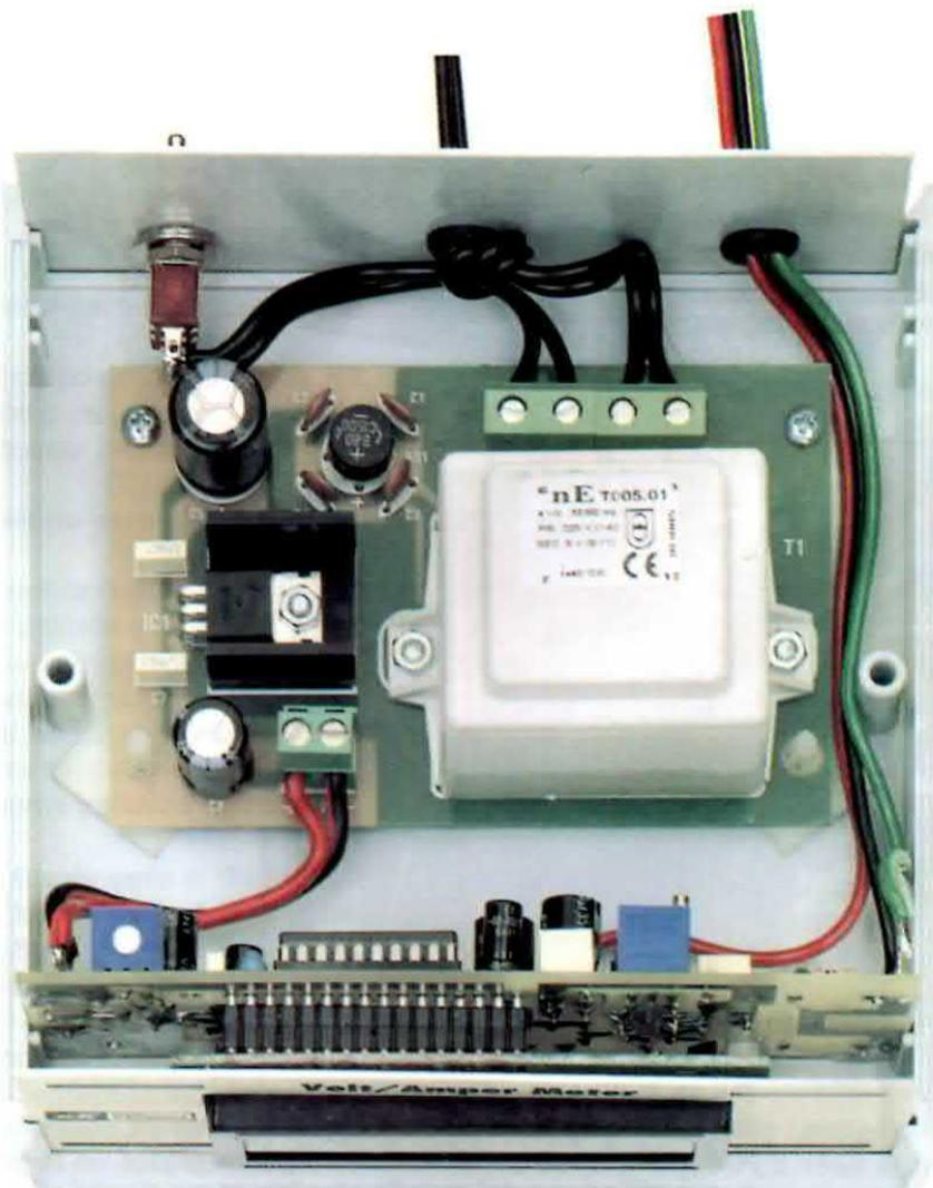
**Fig.14** In questa foto si vede il nostro strumento inserito nel mobile plastico assieme ad un alimentatore stabilizzato in grado di fornire una tensione stabilizzata di 5 volt (vedi figg.15-16). I morsetti +/- di uscita si possono fissare sul pannello posteriore.
