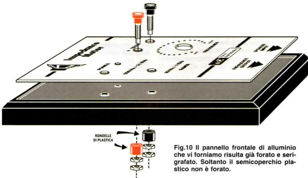
Fig.10 Il pannello frontale di alluminio che vi forniamo risulta già forato e serigrafato. Soltanto il semicoperchio plastico non è forato.
