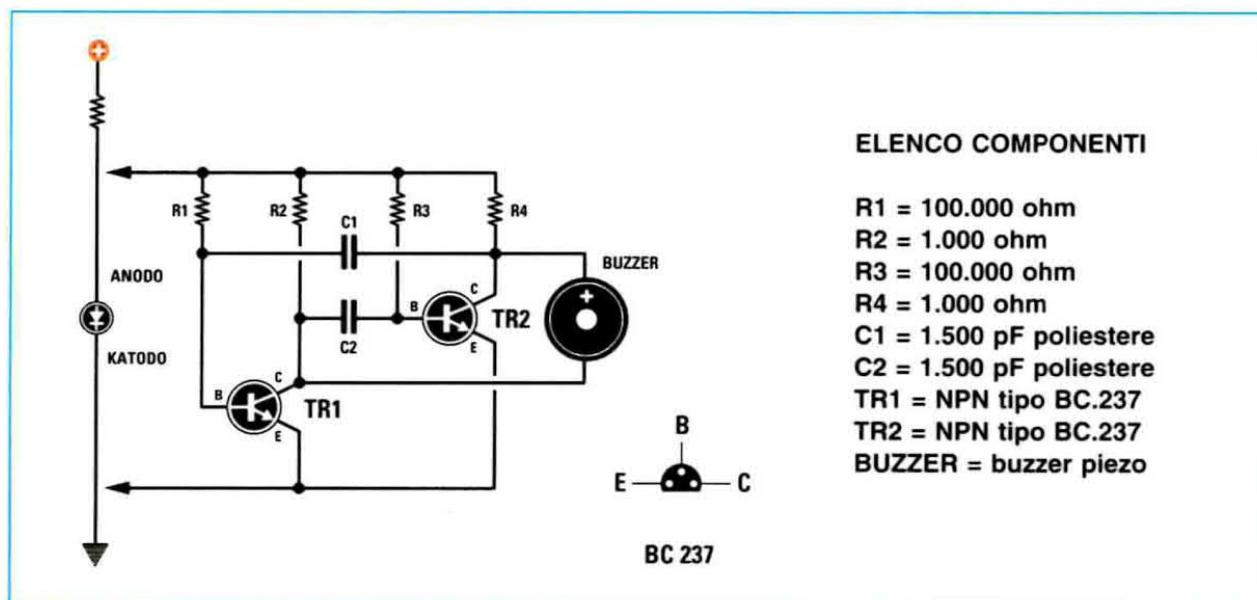
Avendo realizzato il progetto di un termometro a diodo led presentato dalla vostra rivista, mi sono trovato nella necessità di avere una segnalazione acustica ogniqualvolta, al raggiungimento di un determinato valore di temperatura, il diodo led si fosse acceso. Provando e riprovando ho realizzato questo semplice multivibratore composto da due comuni transistor **npn**, che aziona un buzzer idoneo a funzionare anche con basse tensioni.
