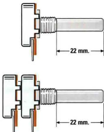
Fig.15 I perni dei due potenziometri R5 e R8-R10 andranno accorciati in modo che abbiano una lunghezza di 22 mm. Dopo aver accorciato i perni, limate le loro estremità per eliminare eventuali sbavature.
