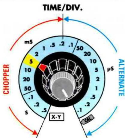
Fig.15 La funzione **CHOPPER** si usa quando il **TIME/DIV.** risulta posizionato sulle portate da 0,5 Sec. a 0,2 milliSec., mentre la funzione **ALTERNATE** quando la stessa manopola risulta posizionata sulle portate da 0,2 milliSec. a 0,1 microSec.
