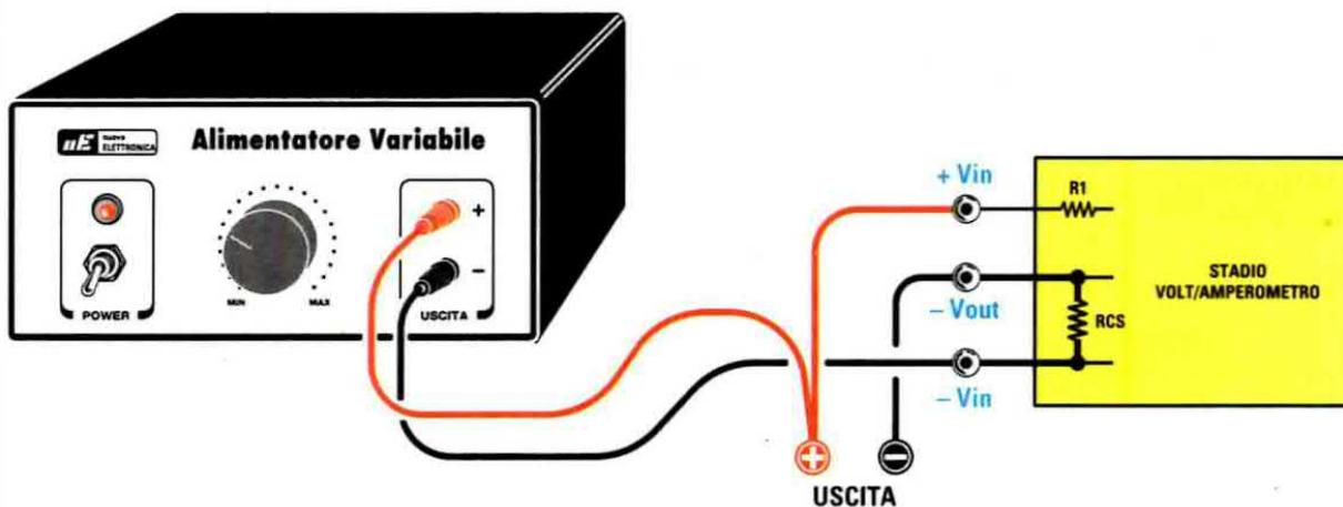
Fig.4 Per leggere il valore di tensione presente sulla boccia d'uscita di un alimentatore e per conoscere quanta corrente assorbe il circuito da alimentare, dovrete collegare il morsetto Positivo dell'alimentatore all'ingresso "+Vin" del nostro circuito e il morsetto Negativo all'ingresso "-Vin", utilizzando poi come polo negativo l'uscita "-Vout".
