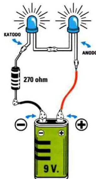
Fig.5 Per alimentare 2 diodi led Blu posti in serie utilizzando una tensione di 9 volt è necessario applicare in serie una resistenza da 270 ohm (vedi 3° esempio).
