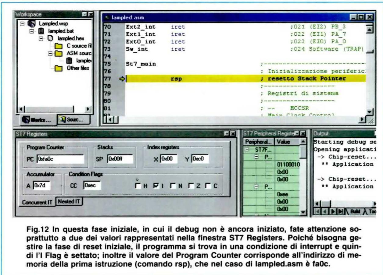
Fig.12 In questa fase iniziale, in cui il debug non è ancora iniziato, fate attenzione soprattutto a due dei valori rappresentati nella finestra ST7 Registers. Poiché bisogna gestire la fase di reset iniziale, il programma si trova in una condizione di interrupt e quindi l'I Flag è settato; inoltre il valore del Program Counter corrisponde all'indirizzo di memoria della prima istruzione (comando **rsp**), che nel caso di **lamped.asm** è **fa0c**.
