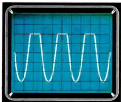
**Fig.8** Applicando sulla Base del transistor che presenta il punto di riposo spostato sul valore di 6,25 volt come visibile in fig.5, un segnale la cui ampiezza supera il massimo valore consentito, il segnale amplificato che uscirà dal suo Collettore risulterà tosato solo sulle semionde positive. Per risolvere il problema conviene sempre ricalcolare il guadagno del transistor per un valore minore.
