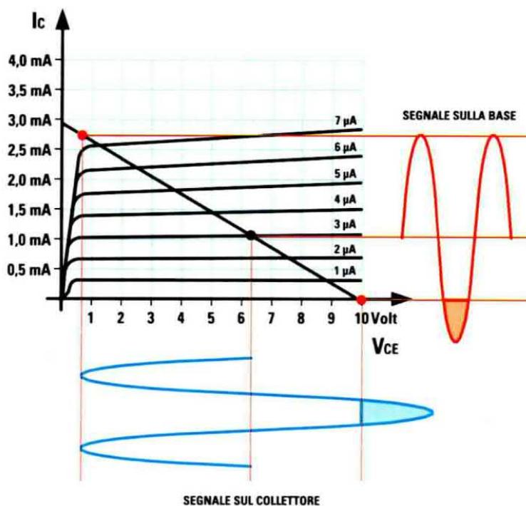
automaticamente varierà anche la **tensione** sul **Collettore**, quindi se guardiamo il tracciato di colore **blu** di fig.5 noteremo che, in **assenza** di segnale sul **Collettore**, otteniamo una tensione di **6,25 volt**, che scenderà a circa **3,75 volt** in presenza delle **semionde positive** e salirà a circa **8,75 volt** in presenza delle **semionde negative**.
