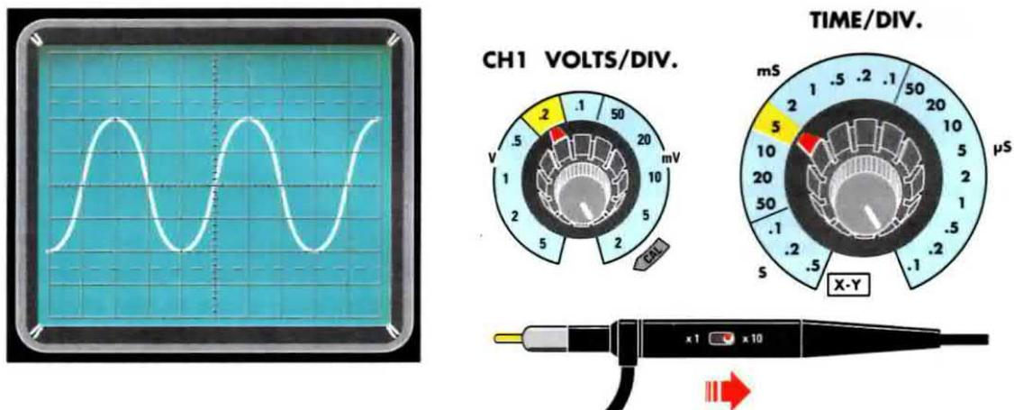
Fig.10 Se il deviatore presente nel puntale è posto su x10, per vedere sullo schermo ancora 4 quadretti, dovrete ruotare la manopola del Volts/div. dalla posizione "2 volt x divisione" alla posizione "0,2 volt x divisione".
