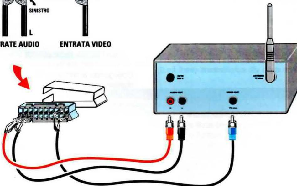
**Fig.12** Per applicare i segnali Audio-Video prelevati dal ricevitore ad una presa Scart per trasferirli ad un TV (vedi fig.13), dovete collegare i tre segnali Audio R-Audio L ai terminali 2-6 e il segnale Video al terminale 20. Non dimenticate di collegare le calze di schermo dei tre cavetti ai terminali di Massa 4 e 17.
