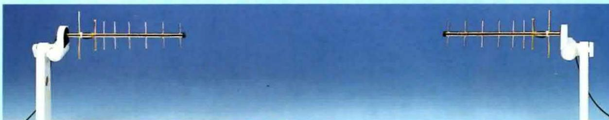
**Fig.14** Potrete collocare gli elementi delle due antenne Yagi in senso Verticale e come visibile nella Tabella sottostante, otterrete sempre un segnale che riesce a raggiungere un valore di 2,4 volt. Nel supporto plastico di queste Yagi sono presenti due viti a galletti per poter muovere l'antenna in ogni posizione.
