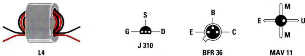
Fig.16 Per realizzare la bobina L4 che viene utilizzata su tutta la gamma dei 50-180 MHz dovreste avvolgere all'interno dei suoi fori 2 spire di filo bifilare di colore diverso. Sulla destra, le connessioni viste da sotto del fet J.310 e del transistor BFR.36 e quelle del MAV11 viste invece da sopra. In prossimità del terminale U troverete un punto "spor-gente" di colore nero che noi abbiamo colorato in "bianco" per renderlo più visibile.
