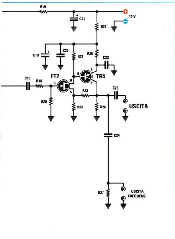
Questo circuito può essere alimentato con una tensione **continua** possibilmente stabilizzata, compresa tra i **10-13 volt**.
