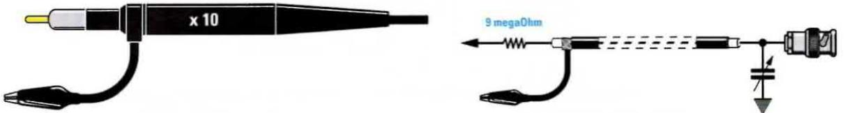
Fig.6 Se sul vostro puntale è riportata la sola indicazione x10, sull'ingresso dell'oscilloscopio giungerà un segnale la cui "ampiezza" risulterà "10 volte minore" rispetto a quella che risulta applicata sull'ingresso del puntale stesso.
