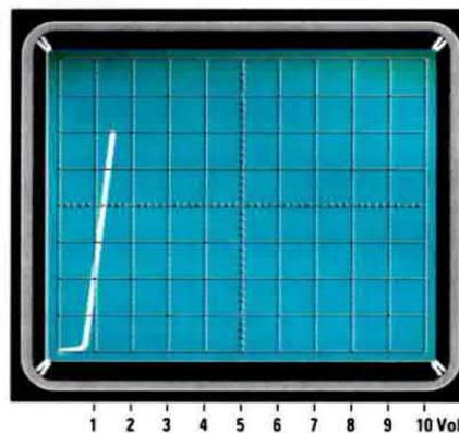
Fig.7 Nella fig.6 vi abbiamo consigliato di partire con una Corrente di Base di 100 microamper perchè potreste avere dei minuscoli diodi SCR o TRIAC che risultano molto sensibili. Per diodi di media sensibilità si parte sempre da una corrente di circa 100  $\mu$ A, si sale poi fino a raggiungere i 500  $\mu$ A ed anche 1 milliamper. I diodi SCR e i diodi TRIAC che riescono ad eccitarsi con correnti non superiori a 1 mA sono da considerarsi molto sensibili.
