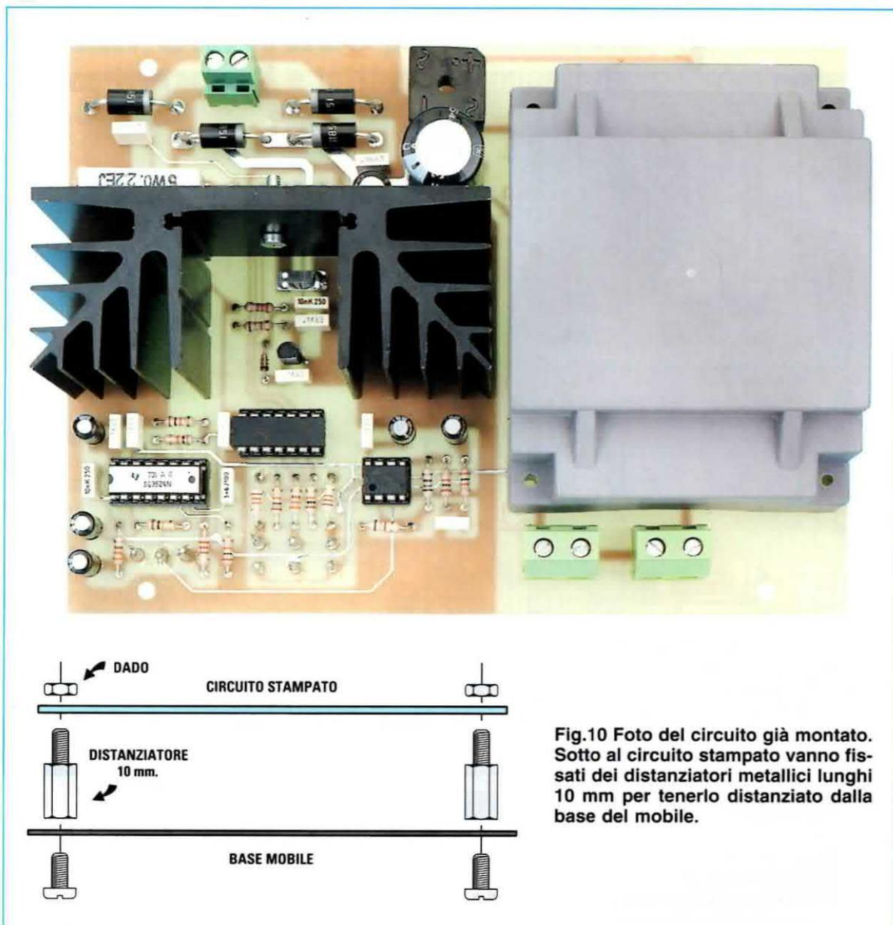
Fig.10 Foto del circuito già montato. Sotto al circuito stampato vanno fissati dei distanziatori metallici lunghi 10 mm per tenerlo distanziato dalla base del mobile.
