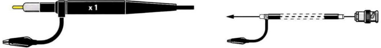
Fig.5 Se sul puntale che utilizzate per eseguire le vostre misure è riportata la sola indicazione x1, sull'ingresso dell'oscilloscopio giungerà un segnale la cui "ampiezza" risulterà perfettamente identica a quella applicata sull'ingresso del puntale stesso.
