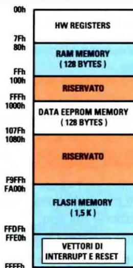
**Fig.15** Mappa della memoria del micro **ST7LITE09**. Le aree da **00h** a **FFh** appartengono ai registri hardware e alla memoria **RAM**. L'indirizzo **38h** appartiene all'area che va da **00h** e **7Fh** e corrisponde al registro **MCCR** che gestisce il clock.
