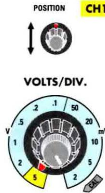
Fig.25 Se avete posto il selettore Volts/div. sulla portata "5 volt" e misurando una tensione CC vedete la traccia orizzontale spostarsi verso l'alto di 1,8 quadretti, questa tensione avrà un valore di  $1,8 \times 5 = 9$  volt.
