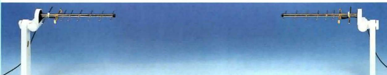
**Fig.16** Collegando due antenne Yagi al Trasmettitore e al Ricevitore, potrete raggiungere e superare una portata di 200-300 metri, sempre che non vi siano ostacoli. Ricordate di collocare gli elementi di entrambe le antenne in senso Orizzontale per ottenere il massimo segnale (vedi Tabella sotto).
