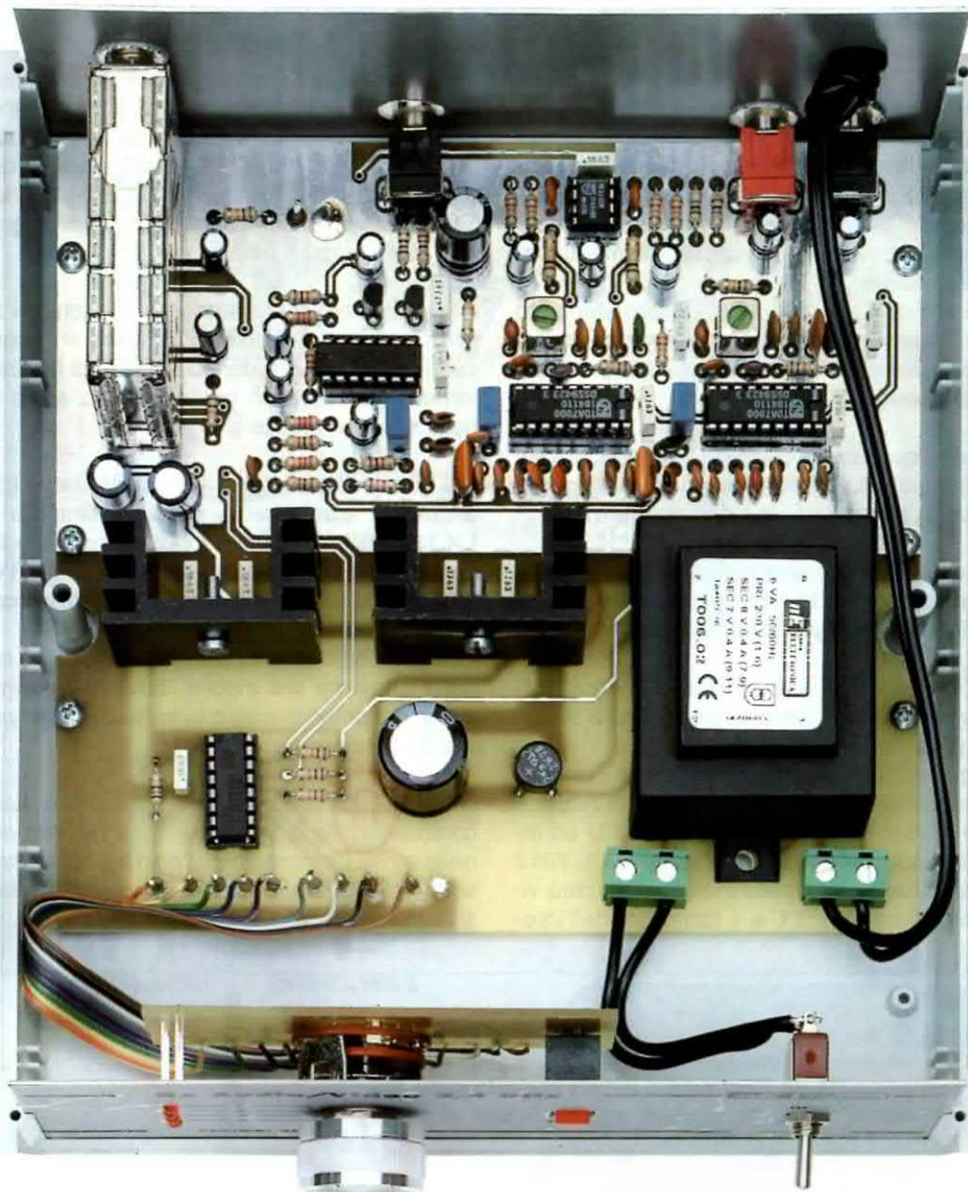
**Fig.9** Dopo aver montato la scheda base LX.1558 la dovrete fissare nel mobile plastico che vi forniamo assieme al kit. Di lato la scheda del cambio gamma da fissare sul pannello frontale.
