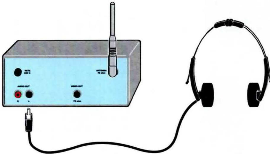
**Fig.11** Dopo aver collegato una cuffia alla boccola d'uscita L del Ricevitore, ruotate il nucleo della bobina MF1 fino ad udire la nota acustica dei 1.000 Hz. Tarata questa bobina, collegate la cuffia alla boccola d'uscita R e poi ruotate il nucleo della bobina MF2 fino ad udire la solita nota acustica dei 1.000 Hz.
