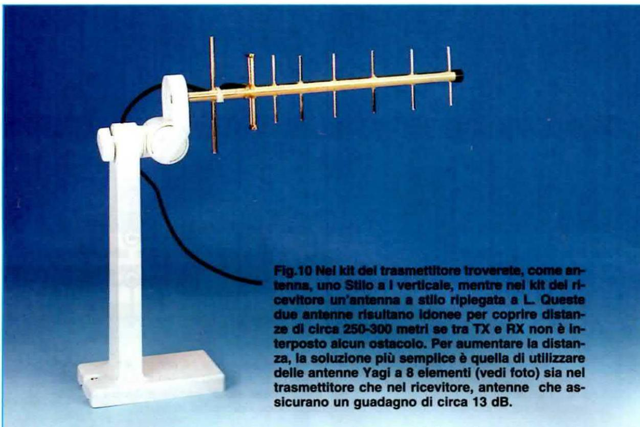
**Fig.10** Nel kit del trasmettitore troverete, come antenna, uno Stilo a l verticale, mentre nel kit del ricevitore un'antenna a stilo ripiegata a L. Queste due antenne risultano idonee per coprire distanze di circa 250-300 metri se tra TX e RX non è interposto alcun ostacolo. Per aumentare la distanza, la soluzione più semplice è quella di utilizzare delle antenne Yagi a 8 elementi (vedi foto) sia nel trasmettitore che nel ricevitore, antenne che assicurano un guadagno di circa 13 dB.
