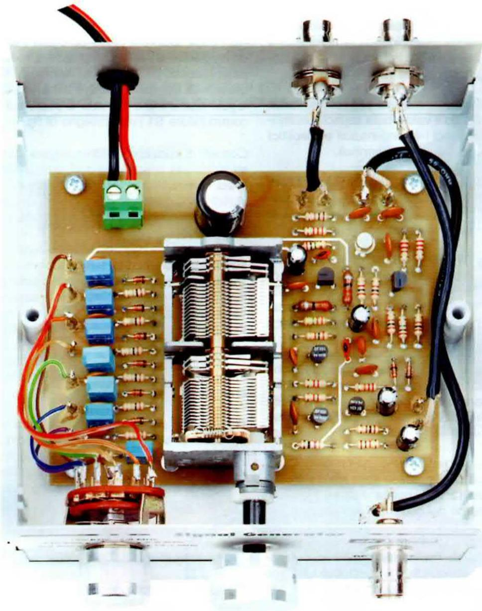
**Fig.6** Completato il montaggio, dovete fissare il circuito stampato all'interno del suo mobile plastico (vedi fig.1) fissandolo con quattro viti autofilettanti nelle torrette già presenti sul piano del mobile stesso. Per i collegamenti ai tre BNC utilizzate degli spezzoni di cavetto coassiale tipo RG.174 che troverete all'interno del kit di montaggio.
