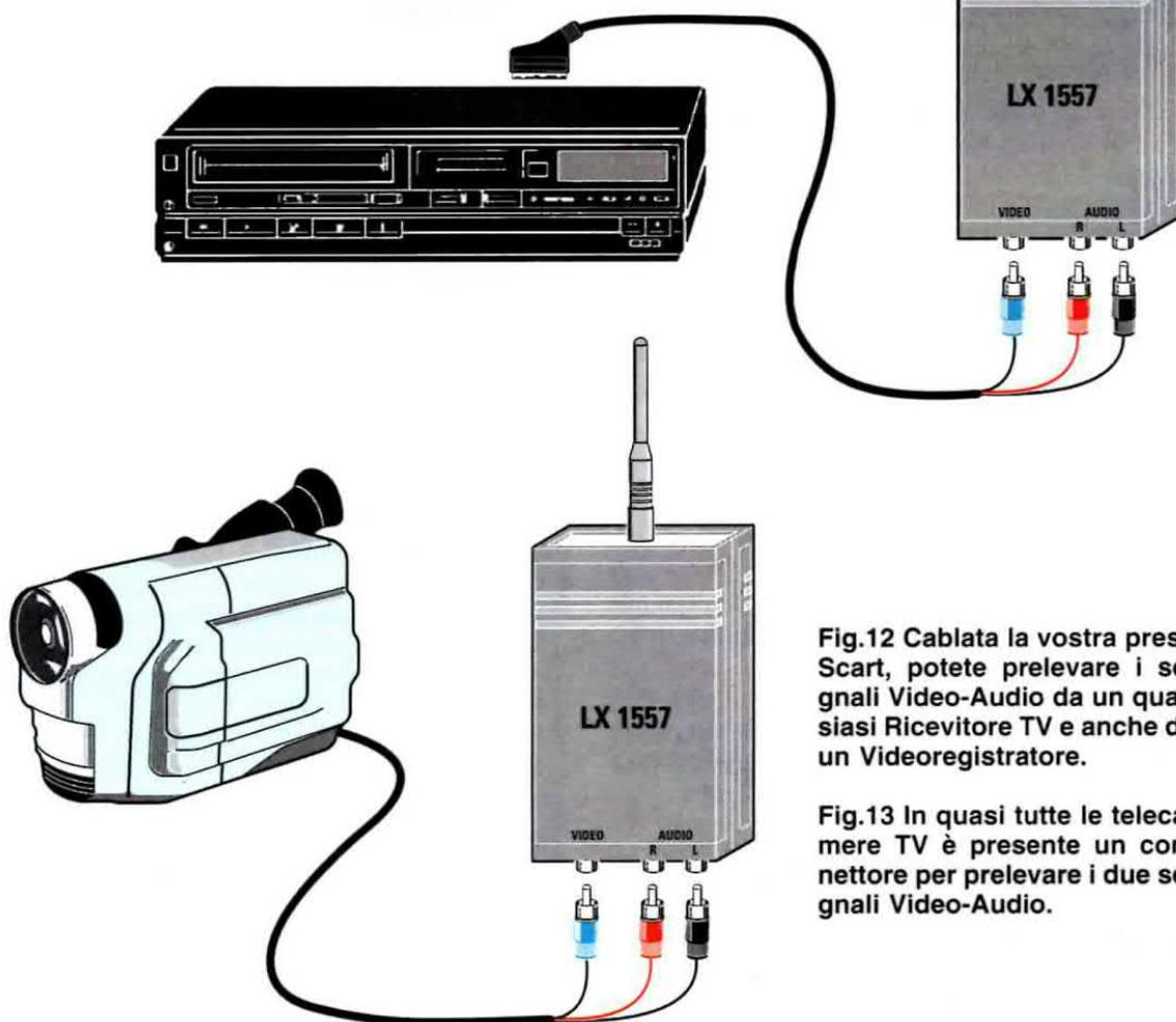
Fig.12 Cablata la vostra presa Scart, potete prelevare i segnali Video-Audio da un qualsiasi Ricevitore TV e anche da un Videoregistratore.
