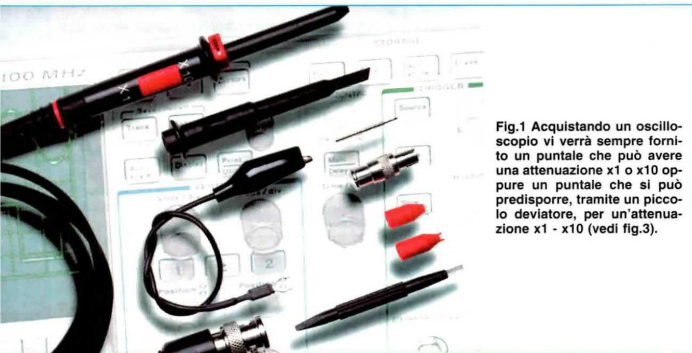
Fig.1 Acquistando un oscilloscopio vi verrà sempre fornito un puntale che può avere una attenuazione x1 o x10 oppure un puntale che si può predisporre, tramite un piccolo deviatore, per un'attenuazione x1 - x10 (vedi fig.3).
