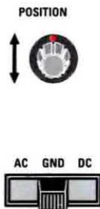
Fig.21 Prima di eseguire la misura di una tensione continua, consigliamo di spostare la levetta del selettore AC-GND-DC su GND e di ruotare poi la piccola manopola "Position" fino a portare la traccia esattamente al centro dello schermo.
