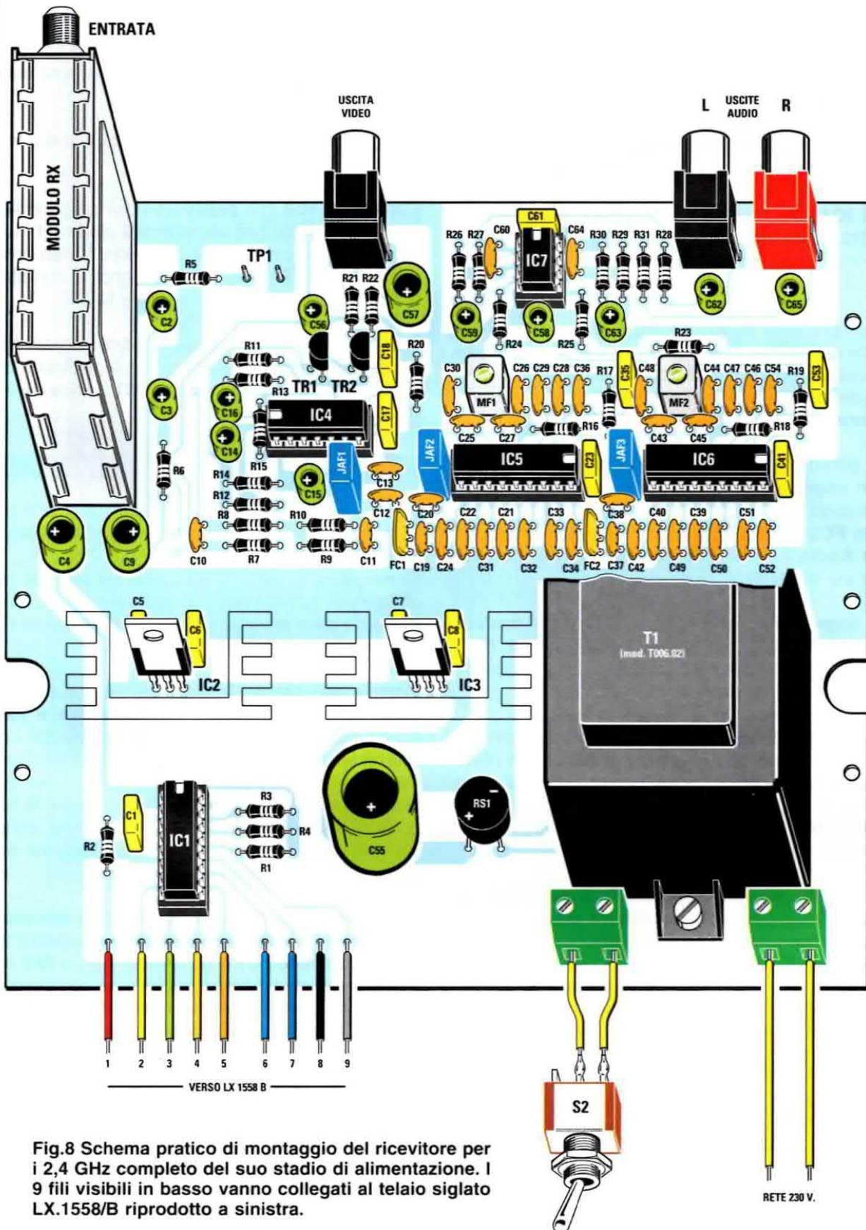
Fig.8 Schema pratico di montaggio del ricevitore per i 2,4 GHz completo del suo stadio di alimentazione. I 9 fili visibili in basso vanno collegati al telaio siglato LX.1558/B riprodotto a sinistra.
