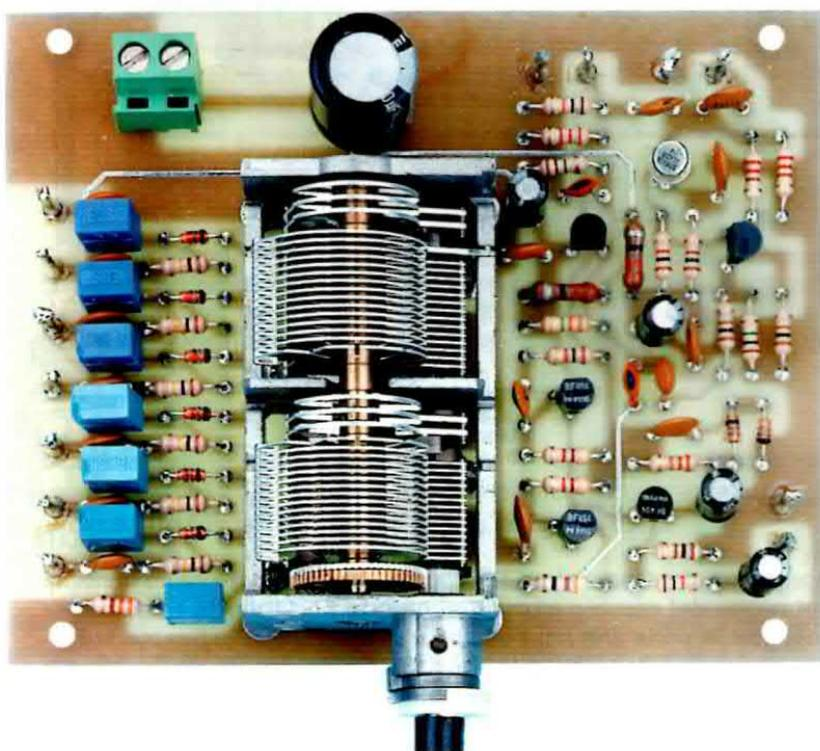
**Fig.3** Foto del circuito stampato con sopra montati tutti i componenti. Si noti il grosso condensatore variabile ad aria siglato **C8** provvisto di perno demoltiplicato. Poiché questo perno risulta molto corto, dovrete inserirvi il tubetto che vi forniamo nel kit (vedi fig.5).
