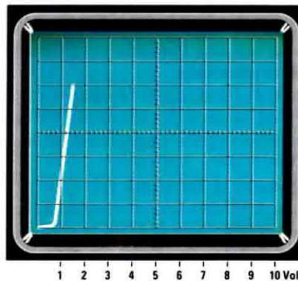
Fig.8 Testando i vari diodi SCR e diodi TRIAC vi accorgete che alcuni di essi, molto sensibili, si eccitano applicando sul loro Gate delle correnti nell'ordine dei microamper ed altri "meno" sensibili che richiedono correnti nell'ordine dei milliamper. Se con il Tracciacurve volete testare un componente che non sapete se è un SCR o un TRIAC, provate a spostare la leva di fig. 2 sulla posizione PNP e, se appare la medesima traccia, il componente è un TRIAC.
