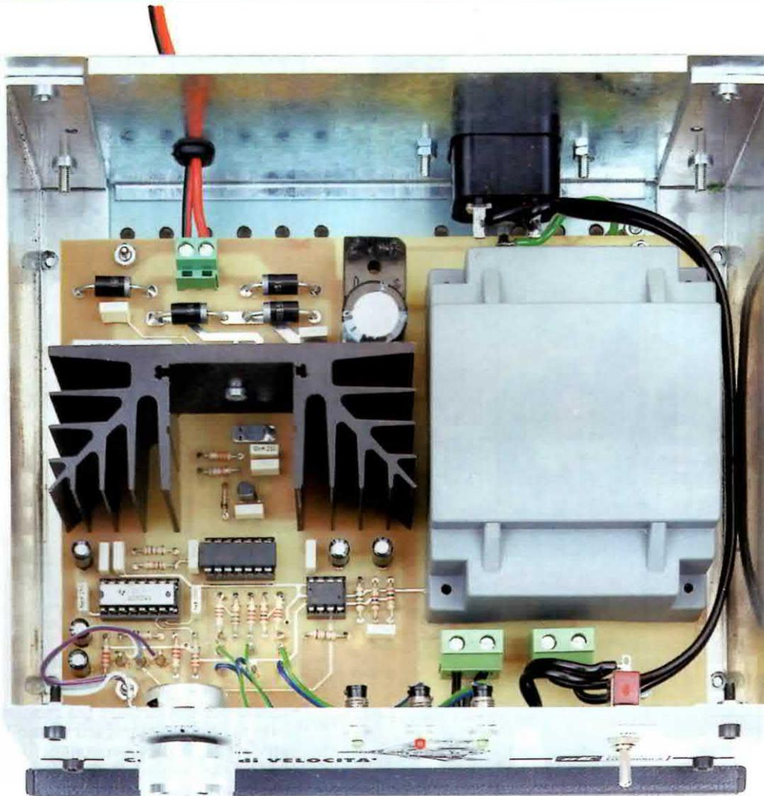
**Fig.11** In questa foto potete vedere come risulta disposto il circuito stampato all'interno del mobile metallico. Facciamo presente che il circuito stampato che forniremo assieme al kit, è completo di disegno serigrafico e di vernice protettiva.
