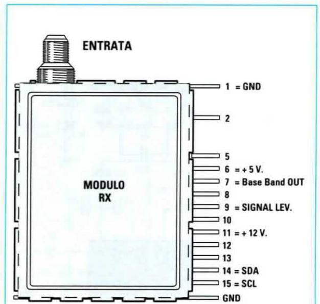
**Fig.5** Il Modulo RX per i 2,4 GHz dispone di 14 terminali compresi i due di Massa indicati GND. Questo modulo va alimentato, sul piedino 6, con una tensione stabilizzata di 5 volt (vedi fig.2). Collegando al piedino 9 un Tester, potrete leggere il valore del segnale captato dal Modulo RX.
