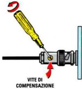
Fig.11 Sul pannello frontale di ogni oscilloscopio è presente un piccolo terminale contrassegnato CAL, dal quale esce un segnale ad onda quadra che serve per tarare la piccola "vite" posta sul corpo del BNC maschio del puntale (vedi fig.3).
