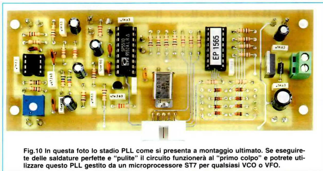
Fig.10 In questa foto lo stadio PLL come si presenta a montaggio ultimato. Se eseguirete delle saldature perfette e "pulite" il circuito funzionerà al "primo colpo" e potrete utilizzare questo PLL gestito da un microprocessore ST7 per qualsiasi VCO o VFO.
