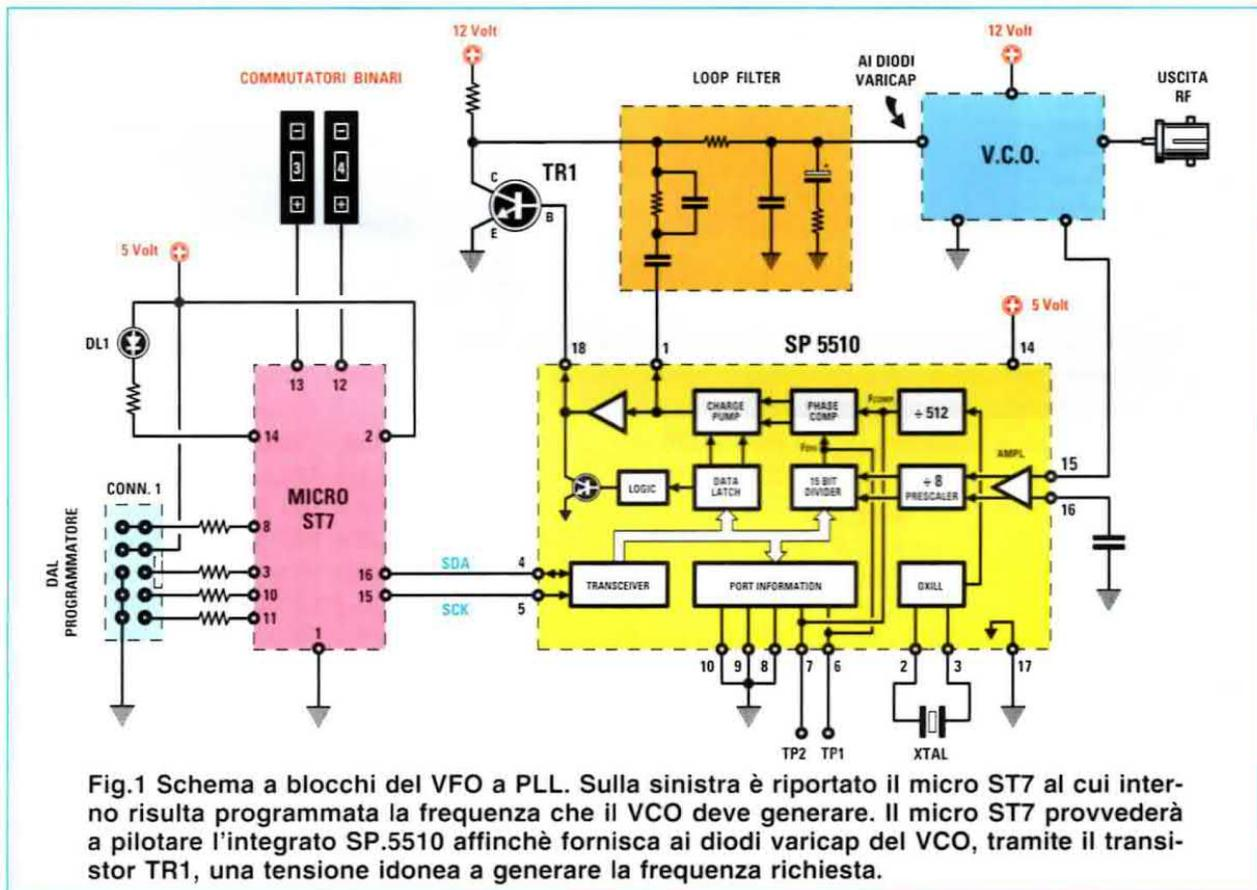
Fig.1 Schema a blocchi del VFO a PLL. Sulla sinistra è riportato il micro ST7 al cui interno risulta programmata la frequenza che il VCO deve generare. Il micro ST7 provvederà a pilotare l'integrato SP.5510 affinché fornisca ai diodi varicap del VCO, tramite il transistor TR1, una tensione idonea a generare la frequenza richiesta.
