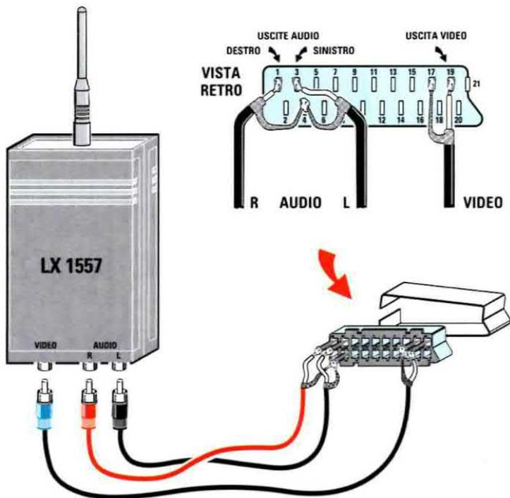
Fig.11 In questo disegno potete vedere da dove si prelevano, tramite cavetti schermati, i segnali Video e Audio in una presa Scart.
