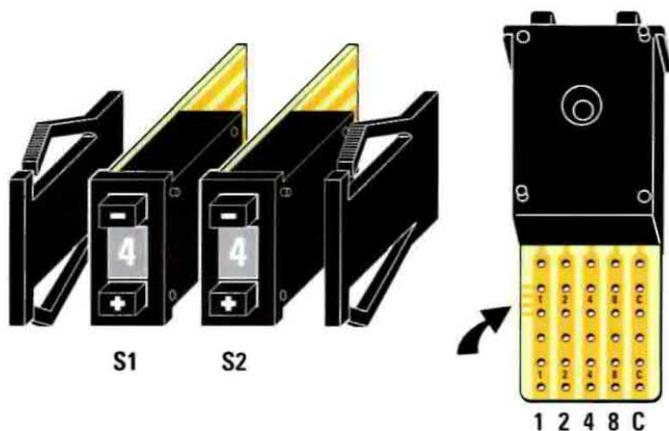
Fig.9 Dal corpo dei commutatori binari esce un ritaglio di circuito stampato provvisto di 5 piste in rame sul quale dovete collegare i fili 1-2-4-8-C che escono dal circuito del PLL. I fili indicati "verso S1" vanno collegati al commutatore di sinistra e quelli indicati "verso S2" al commutatore di destra. All'interno di queste 5 piste sono incisi con caratteri appena visibili i numeri 1-2-4-8-C.
