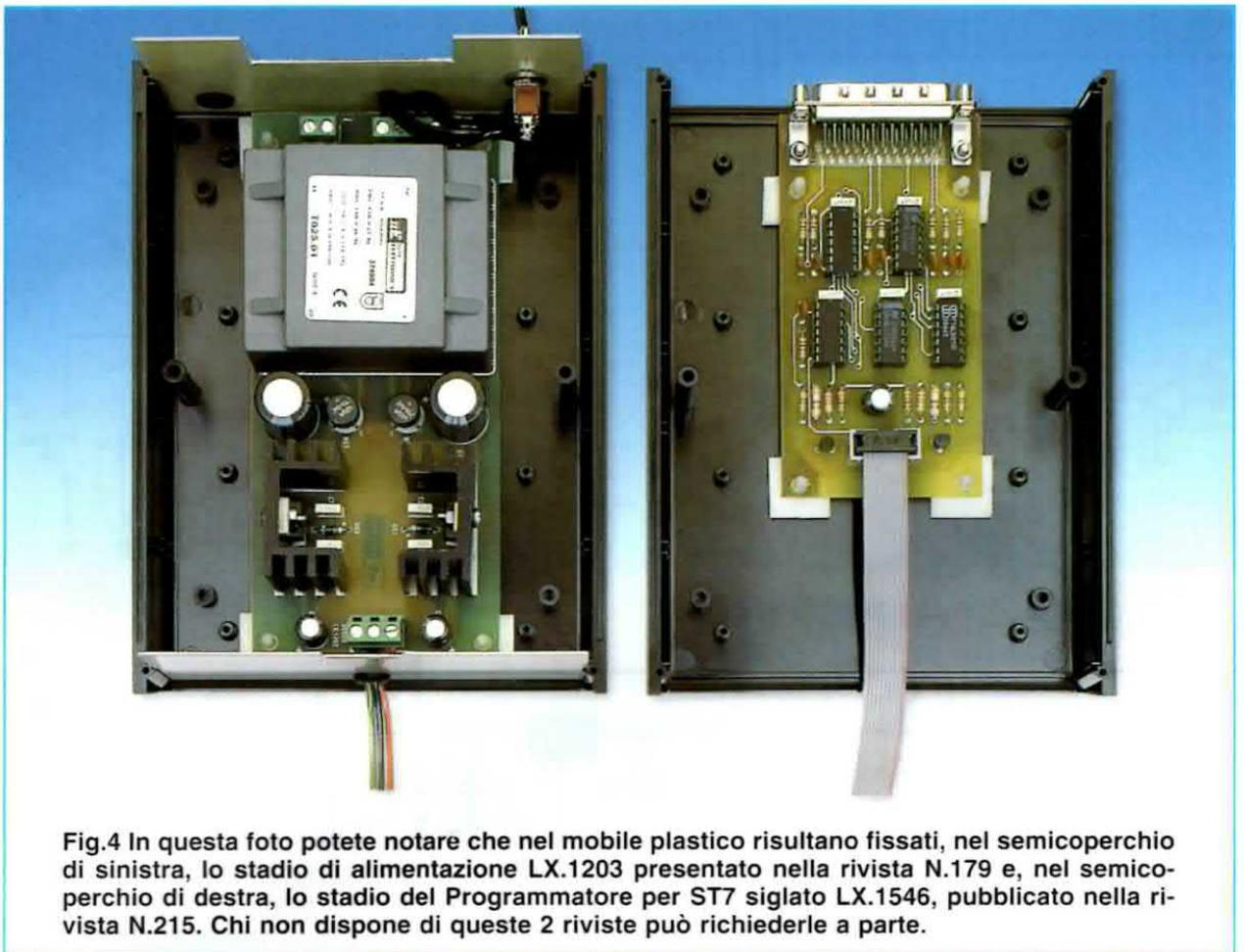
Fig.4 In questa foto potete notare che nel mobile plastico risultano fissati, nel semicoperchio di sinistra, lo stadio di alimentazione LX.1203 presentato nella rivista N.179 e, nel semicoperchio di destra, lo stadio del Programmatore per ST7 siglato LX.1546, pubblicato nella rivista N.215. Chi non dispone di queste 2 riviste può richiederle a parte.
