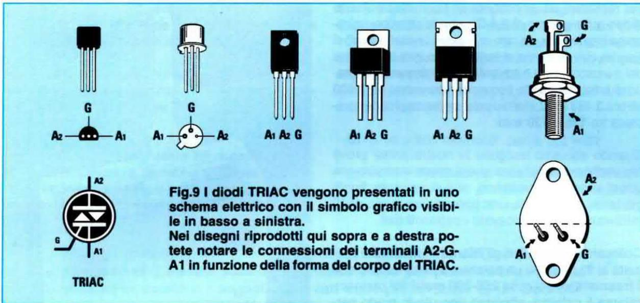
**Fig.9** I diodi TRIAC vengono presentati in uno schema elettrico con il simbolo grafico visibile in basso a sinistra. Nei disegni riprodotti qui sopra e a destra potete notare le connessioni dei terminali A2-G-A1 in funzione della forma del corpo del TRIAC.
