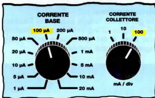
**Fig.3** Per testare qualsiasi SCR e TRIAC dovete ruotare sul pannello frontale del Tracciacurve, la manopola della Corrente di Base su 100 microamper e quella della Corrente di Collettore su 100 milliamper/div.
