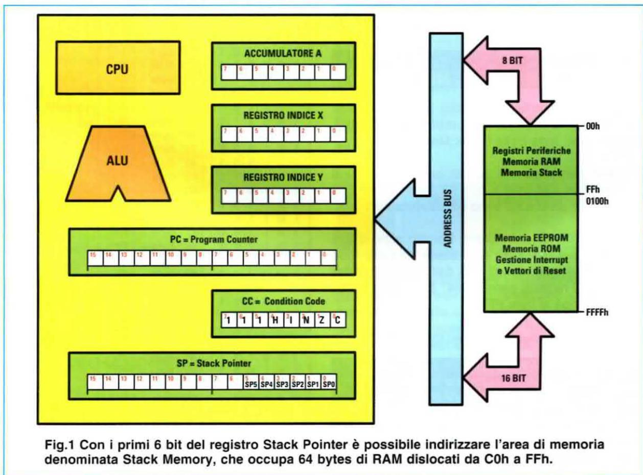
Fig.1 Con i primi 6 bit del registro Stack Pointer è possibile indirizzare l'area di memoria denominata Stack Memory, che occupa 64 bytes di RAM dislocati da C0h a FFh.
