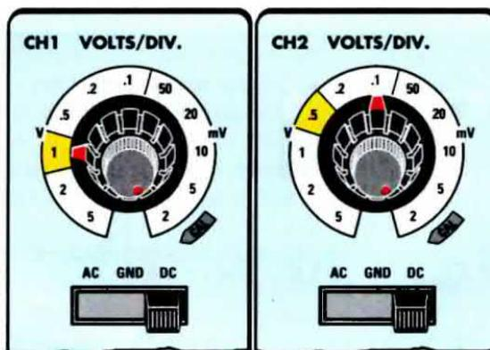
**Fig.4** La manopola CH1 dell'oscilloscopio dovrà essere posta sulla portata "1 volt per divisione" e la manopola CH2 sulla portata "0,5 volts per divisione". Questo vale sia per i diodi SCR che per i TRIAC.
