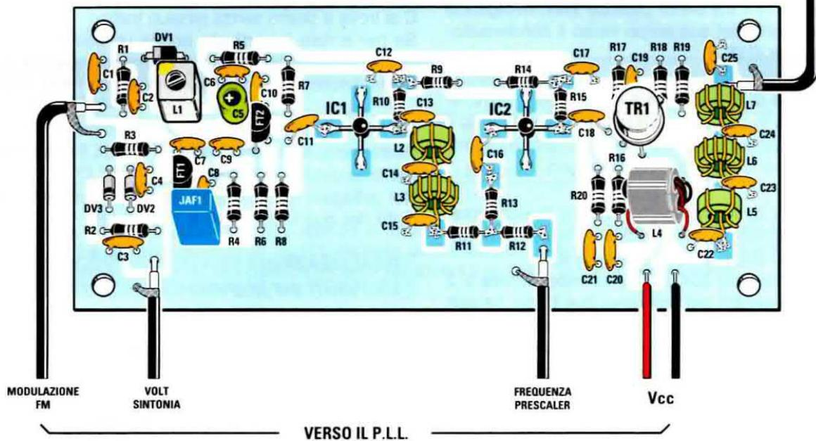
Fig.15 Schema pratico di montaggio dello stadio VCO. Vi ricordiamo che in funzione della loro gamma di lavoro, dovreste utilizzare per le bobine e per i condensatori dei valori diversi che trovate riportati nelle figg.11-12-13. I cavetti coassiali visibili in basso in questo schema vanno collegati al circuito stampato del PLL come evidenziato in fig.17.
