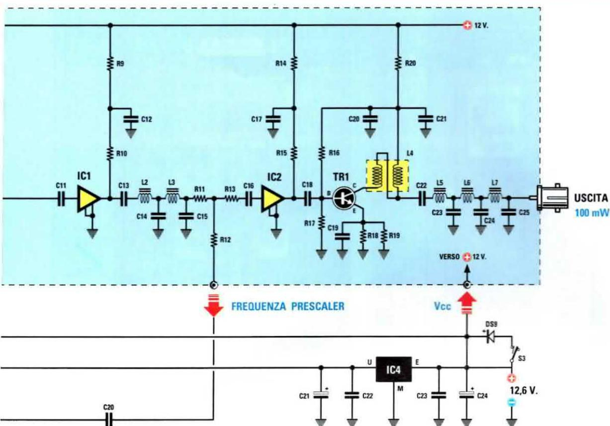
Fig.3 I componenti racchiusi all'interno della fascia blu appartengono allo stadio VCO che abbiamo siglato LX.1566 (vedi fig.15). In basso a destra, elenco componenti del VCO.
