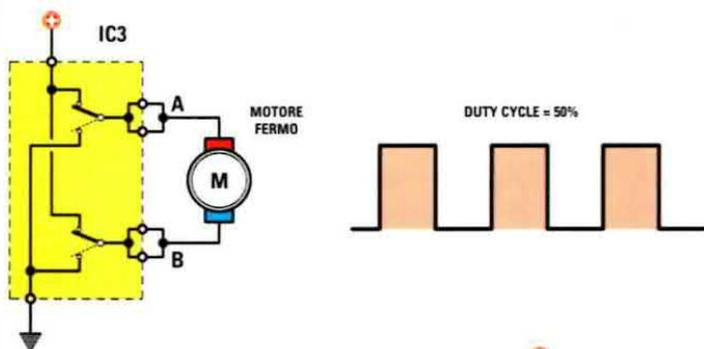
Fig.4 Ruotando la manopola del potenziometro R2 a metà corsa, dall'integrato IC3 esce un'onda quadra con un duty-cycle del 50% e con questo tipo di forma d'onda il motore rimane in Stop.
