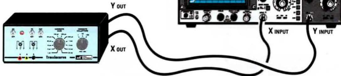
Anche spostando il deviatore del **tracciacurve** dalla posizione **TR** alla posizione **FET** il diodo **SCR** non potrà eccitarsi, perchè sul **Gate** occorre sempre applicare una tensione di **polarità positiva**.
