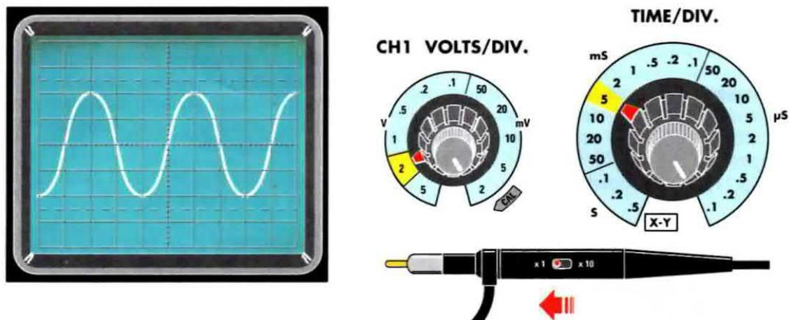
Fig.8 Se sullo schermo dell'oscilloscopio appare un segnale sinusoidale che raggiunge un'ampiezza di 4 quadretti e la manopola del Volts/div. è posta sulla posizione "2 volt x divisione", l'ampiezza del segnale sarà di  $4 \times 2 = 8$  volt picco/picco.
