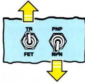
**Fig.2** Per testare qualsiasi tipo di diodo SCR o di diodo TRIAC dovete spostare la levetta del primo deviatore TR-FET sulla scritta "TR" e la levetta del secondo deviatore PNP-NPN sulla scritta "NPN".
