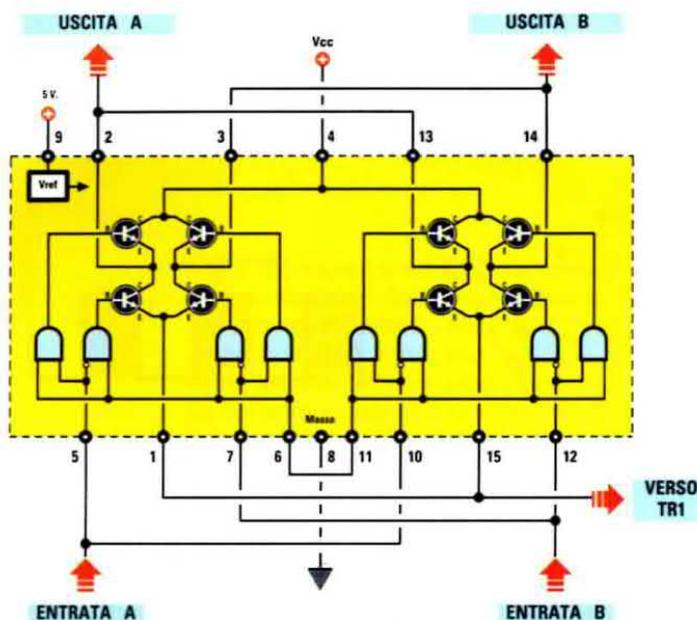
piedino d'uscita 16 una tensione stabilizzata di 5 volt; tale tensione ci servirà per alimentare il potenziometro R2, i 4 Nand contenuti all'interno dell'integrato 4093 (vedi IC2) e i piedini 9-11-6 dell'integrato L.298/N (vedi IC3) compreso il transistor TR1.
