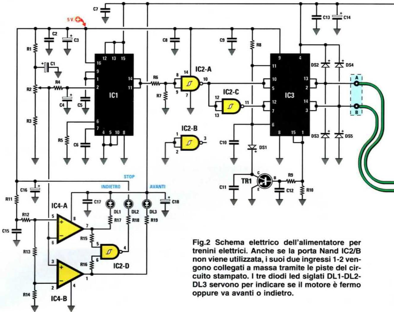
Fig.2 Schema elettrico dell'alimentatore per trenini elettrici. Anche se la porta Nand IC2/B non viene utilizzata, i suoi due ingressi 1-2 vengono collegati a massa tramite le piste del circuito stampato. I tre diodi led siglati DL1-DL2-DL3 servono per indicare se il motore è fermo oppure va avanti o indietro.
