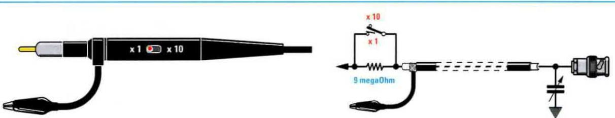
Fig.7 Se sul vostro puntale è riportata l'indicazione x1-x10, sull'ingresso del vostro oscilloscopio potrete far giungere un segnale la cui "ampiezza" risulti pari oppure attenuata di 10 volte rispetto a quella applicata sull'ingresso del puntale.
