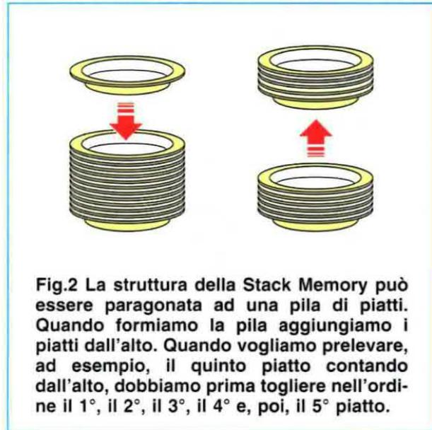
Fig.2 La struttura della Stack Memory può essere paragonata ad una pila di piatti. Quando formiamo la pila aggiungiamo i piatti dall'alto. Quando vogliamo prelevare, ad esempio, il quinto piatto contando dall'alto, dobbiamo prima togliere nell'ordine il 1°, il 2°, il 3°, il 4° e, poi, il 5° piatto.
