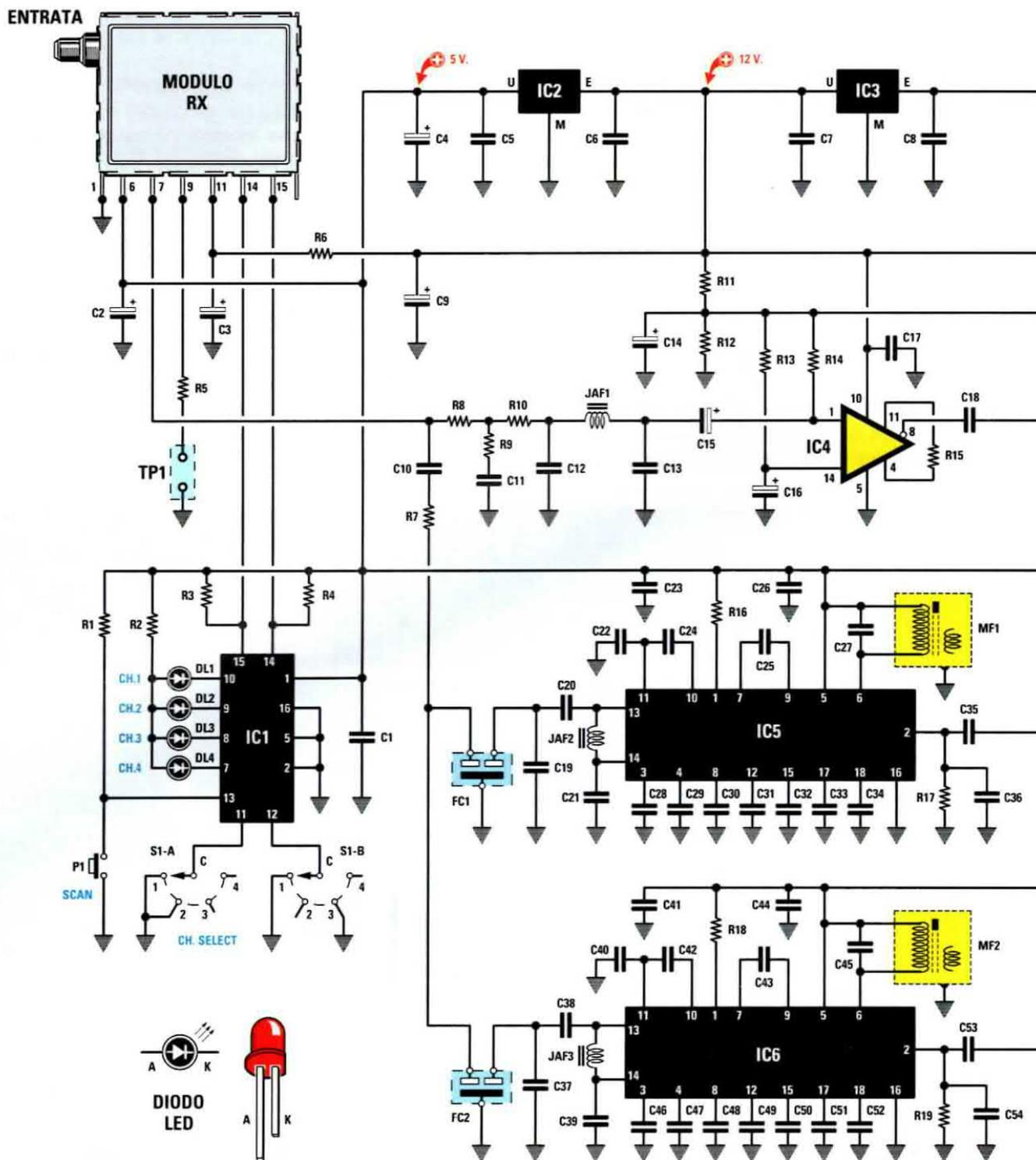
Fig.2 Schema elettrico completo dello stadio ricevente. Collegando un Tester ai terminali TP1 collegati tra il piedino 9 e la Massa del Modulo RX leggerete una tensione in Volt e se consultate la Tabella N.1 riprodotta accanto alla fig.5 potete conoscere il valore del segnale captato espresso in "millivolt". L'elenco dei componenti relativi a questo schema elettrico è riportato nella pagina successiva.
