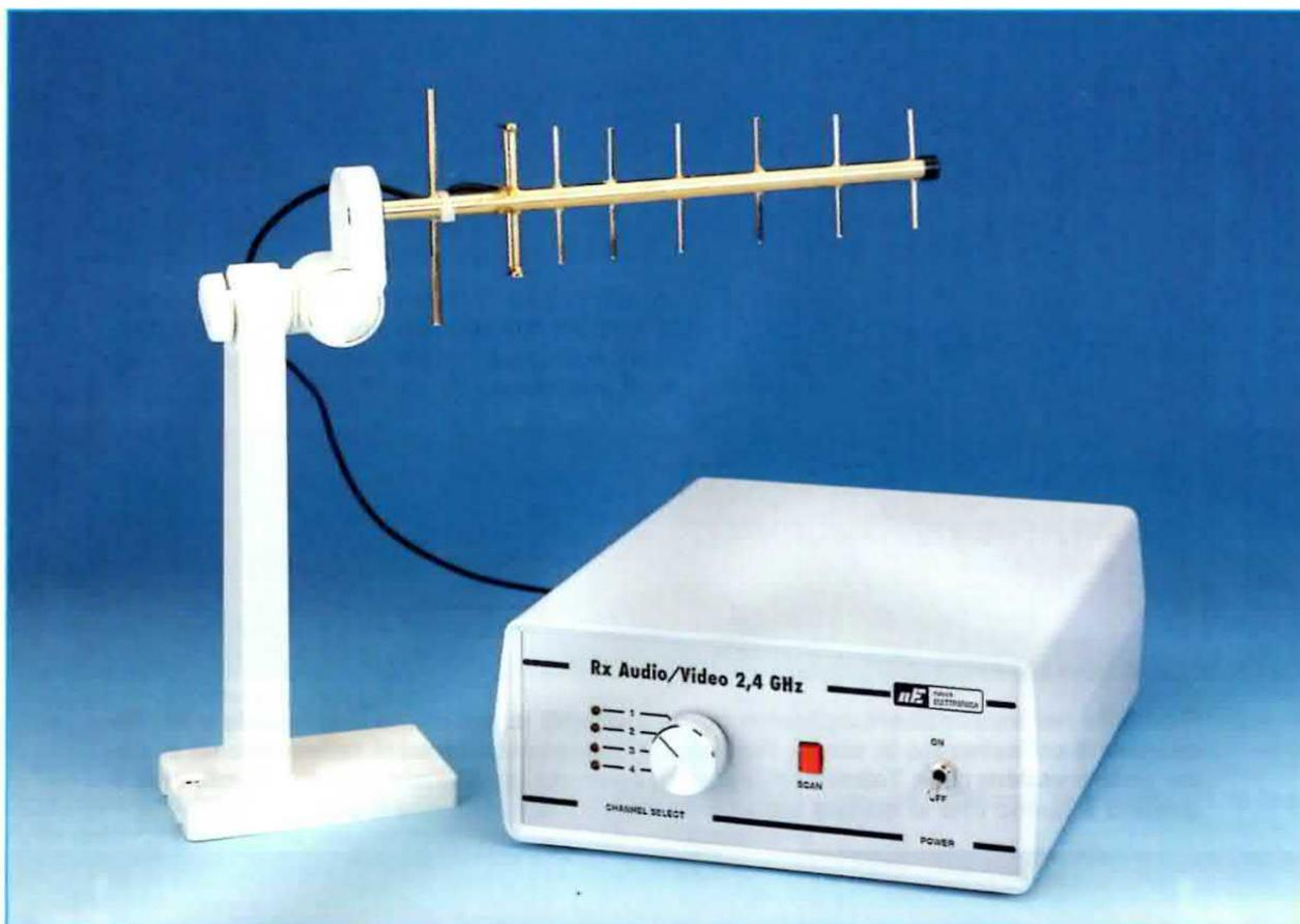
**Fig.18** Se il Trasmettitore e il Ricevitore vengono collocati in due posizioni "fisse", allora si può installare sia sull'uno che sull'altro un'antenna Yagi a 8 elementi per aumentarne le portate. Se il Trasmettitore non viene spostato in continuità, conviene fissare su esso lo Stilo a "I" ed utilizzare l'antenna Yagi solo nel Ricevitore, dirigendola verso il trasmettitore.
