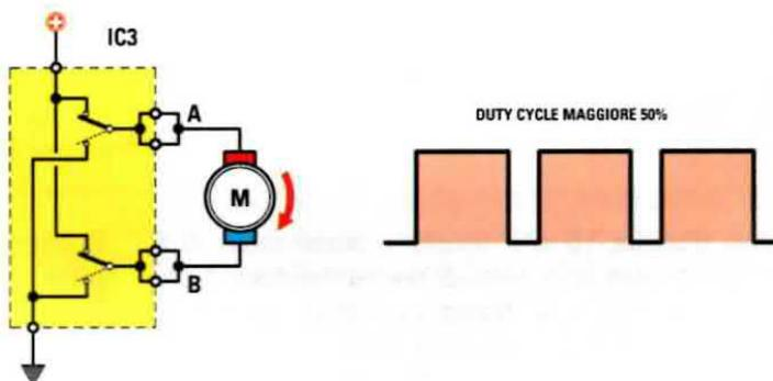
Fig.6 Ruotando la manopola del potenziometro R2 in senso antiorario, dall'integrato IC3 esce un'onda quadra con un duty-cycle minore del 50% e con questa onda il motore ruota all'indietro.
