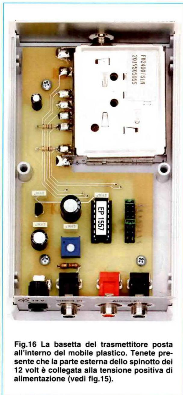
Fig.16 La basetta del trasmettitore posta all'interno del mobile plastico. Tenete presente che la parte esterna dello spinotto dei 12 volt è collegata alla tensione positiva di alimentazione (vedi fig.15).
