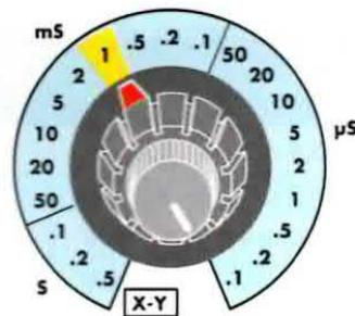
Fig.18 Per le misure in CC conviene posizionare la manopola Time/div. sulla portata "1 millisecondo", perchè questa farà apparire sullo schermo una traccia orizzontale perfettamente continua.
