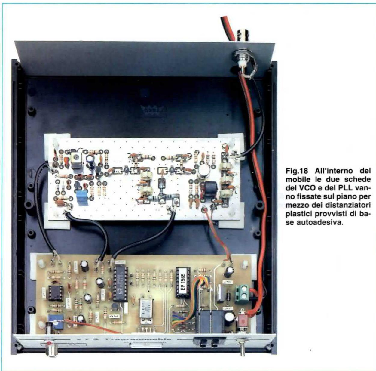
Fig.18 All'interno del mobile le due schede del VCO e del PLL vanno fissate sul piano per mezzo dei distanziatori plastici provvisti di base autoadesiva.
