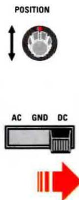
Fig.23 Se invece vedete la traccia orizzontale spostarsi verso il basso, potete essere certi che la tensione applicata sul puntale è di polarità Negativa. La manopola dei Volts/div. va posta sulla portata dei volt che volete misurare.
