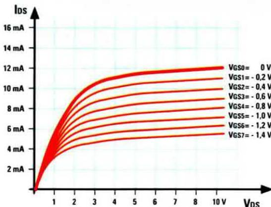
Fig.13 Sull'asse verticale "I<sub>ds</sub>" è riportata la Corrente di Drain, mentre sull'asse orizzontale la tensione "V<sub>ds</sub>" Drain-Source. Nelle 8 tracce è riportato il valore della tensione Negativa presente sul Gate.
