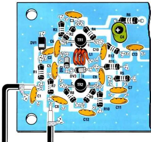
Fig.18 In questo disegno abbiamo notevolmente ingrandito lo stadio oscillatore composto dai due transistor TR1-TR2 perchè possiate vedere meglio come e dove inserire i componenti richiesti. Il terminale Collettore (terminale più lungo) del transistor TR1 va rivolto verso destra, mentre il terminale Collettore di TR2 va rivolto verso sinistra. Il terminale Emettore di TR1 va rivolto verso la bobina L1, mentre il terminale Emettore di TR2 va rivolto verso il vari-cap DV3.
