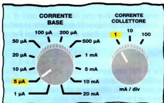
Fig.23 Spostati i deviatori di fig.11 su FET e su NPN dovreste ruotare la manopola della Corrente di Base sui 5  $\mu$ A, che corrispondono ad una tensione di 0,05 Volt x quadretto (vedi fig.7).
