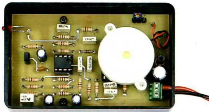
**Fig.15** In questa foto potete vedere il foro praticato sul laterale del mobiletto per far fuoriuscire il diodo led DL1 che, come visibile in fig.12, abbiamo ripiegato a L e quelli che dovrete praticare in corrispondenza del diodo ricevente DRX1 e, sul coperchio, della cicalina.
