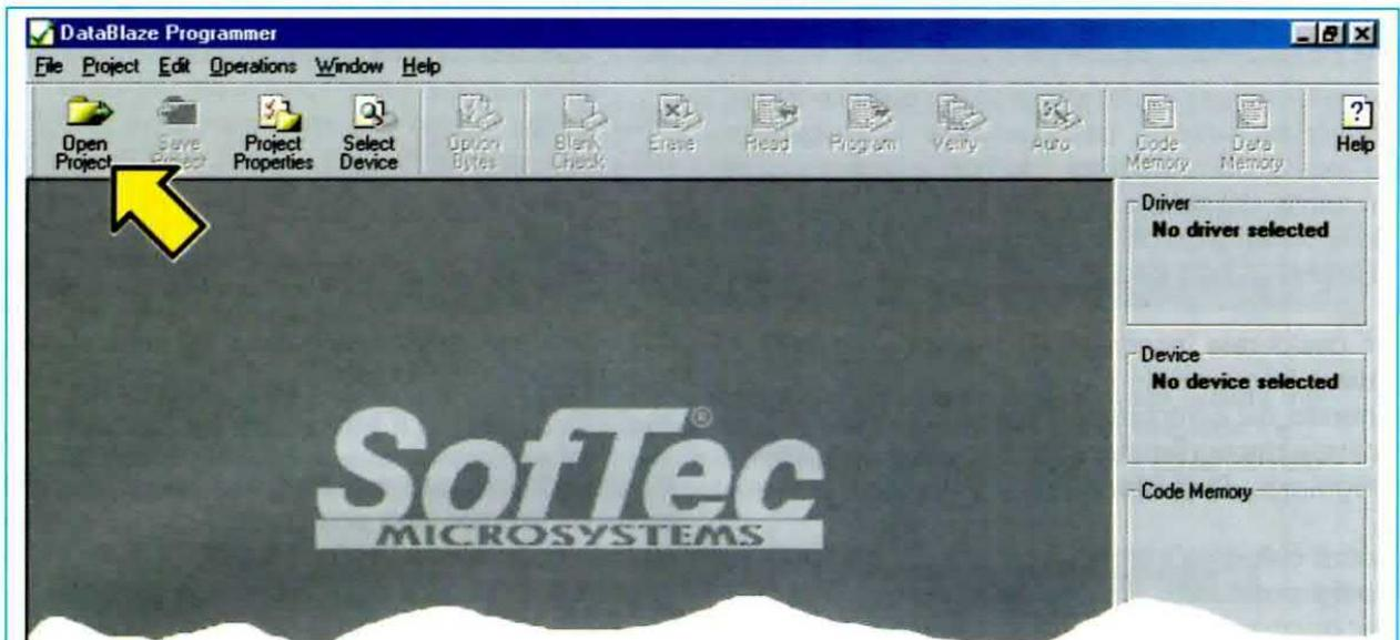
Fig.37 Dopo aver eseguito l'intera sequenza indicata in fig.36, sul video comparirà la finestra del programma DataBlaze. Per aprire il file "Vco.mpp", che servirà per memorizzare la frequenza nel micro ST7, cliccate sull'icona Open Project (vedi freccia).
