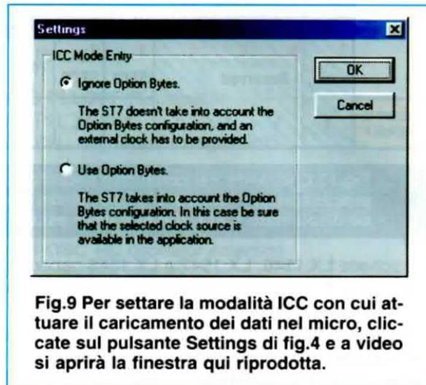
**Fig.9** Per settare la modalità ICC con cui attuare il caricamento dei dati nel micro, cliccate sul pulsante Settings di fig.4 e a video si aprirà la finestra qui riprodotta.
