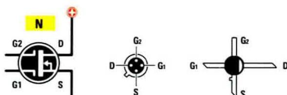
**Fig.21** I Mosfet hanno un doppio Gate siglato G1 e G2. Utilizzando il nostro tracciacurve potrete facilmente controllare se un qualsiasi Mosfet risulta efficiente e anche quanto guadagna.
