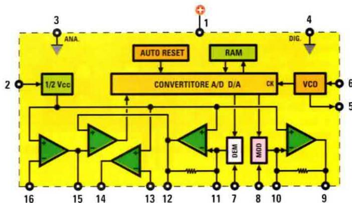
**logico**, è sincronizzata da un **VCO** interno (Voltage Controlled Oscillator - oscillatore controllato in tensione).
