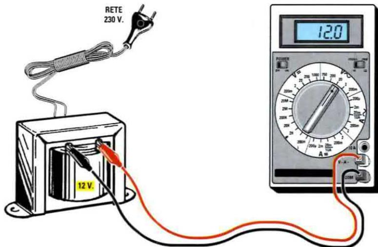
Fig.8 Se disponete di un trasformatore il cui secondario eroga 12 volt e misurate questa tensione con un comune Tester, questo rileverà un valore di 12 volt dal momento che questi strumenti leggono i reali Volt Efficaci.
