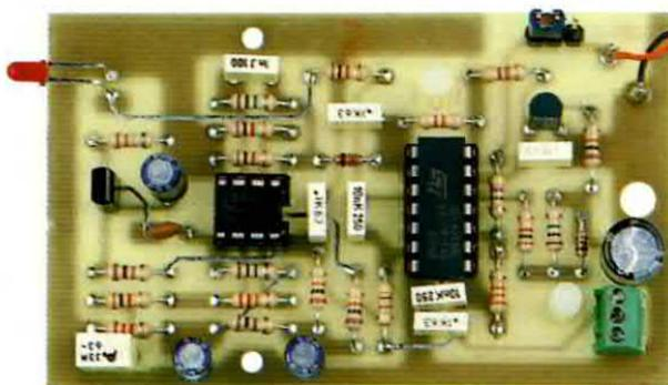
Fig.13 Foto del circuito stampato LX.1569 con già sopra montati tutti i suoi componenti.
