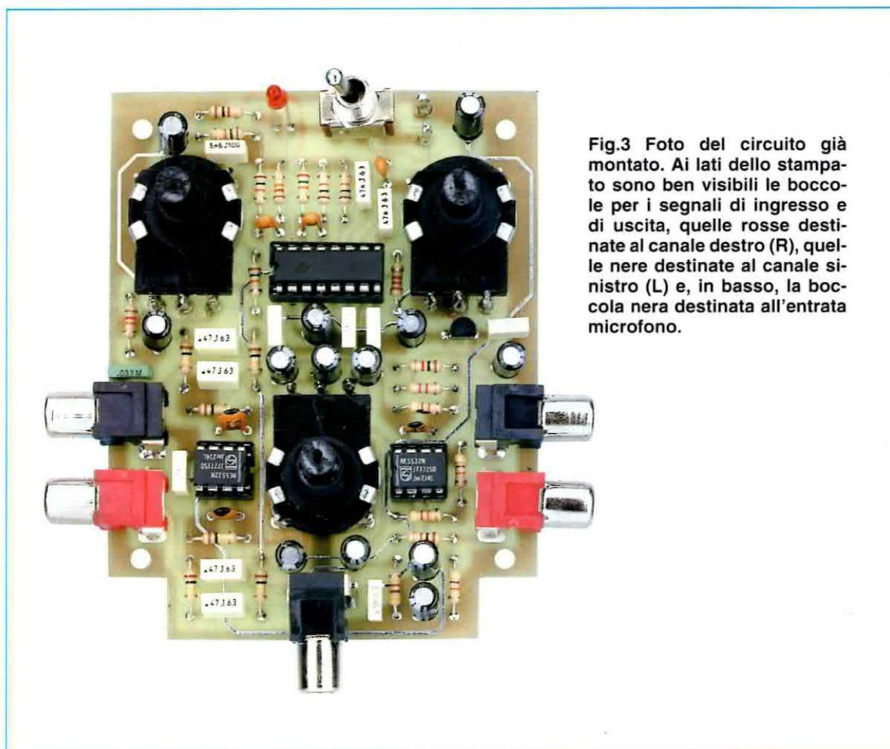
**Fig.3** Foto del circuito già montato. Ai lati dello stampato sono ben visibili le boccole per i segnali di ingresso e di uscita, quelle rosse destinate al canale destro (R), quelle nere destinate al canale sinistro (L) e, in basso, la boccia nera destinata all'entrata microfono.
