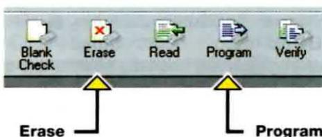
Fig.8 In questa figura abbiamo riprodotto le due icone del programma **DataBlaze** che servono per cancellare (vedi **Erase**) e programmare (vedi **Program**) il microprocessore.
