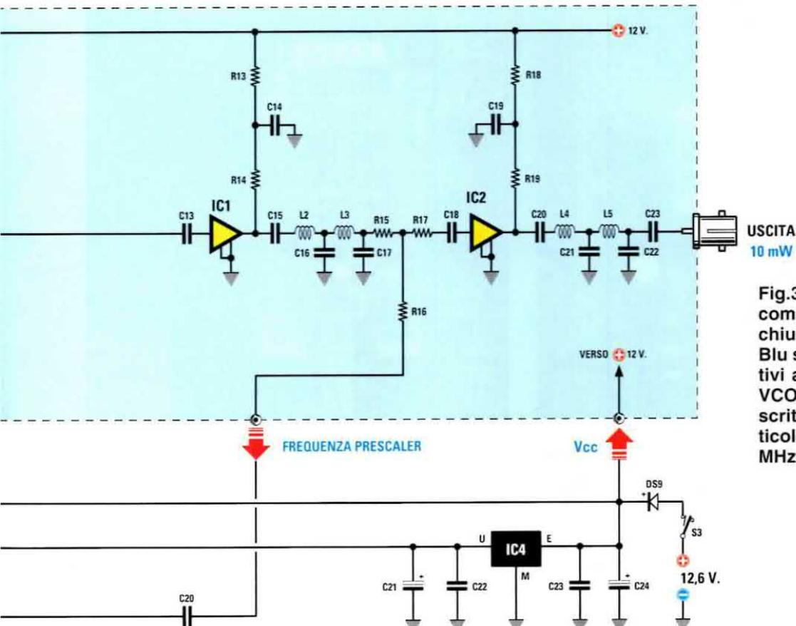
Fig.3 In basso, i componenti racchiusi nel riquadro Blu sono quelli relativi allo schema del VCO LX.1567 descritto in questo articolo, che va da 180 MHz a 730 MHz.
