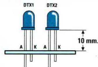
Fig.9 Quando inserite i diodi trasmettenti CQX.89 nel circuito stampato, dovete lasciare i loro terminali lunghi circa 10 mm. Ricordatevi che il terminale A, che risulta più lungo del K, va rivolto verso R5-R7 (vedi fig.7).
