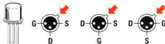
Fig.4 Le connessioni G-S-D, viste da sotto, di un Fet con corpo metallico. Sul corpo metallico di questi Fet è sempre presente una piccola sporgenza di riferimento. Anche in questi Fet la disposizione G-S-D può variare da sigla a sigla.
