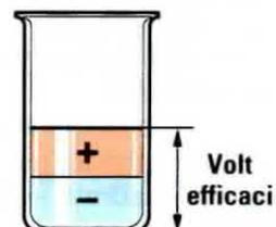
Fig.15 I "Volt picco-picco" si possono paragonare a due "coni" di ghiaccio posti uno sopra all'altro, mentre i "Volt efficaci" al livello dell'acqua ottenuto dai due coni dopo che si sono liquefatti. Ovviamente in quest'ultimo caso il livello raggiunto risulterà minore.
