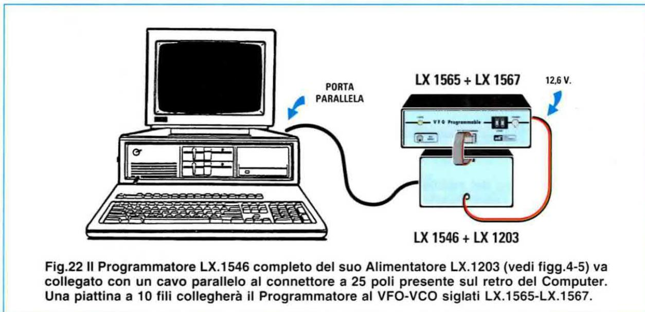
Fig.22 Il Programmatore LX.1546 completo del suo Alimentatore LX.1203 (vedi figg.4-5) va collegato con un cavo parallelo al connettore a 25 poli presente sul retro del Computer. Una piattina a 10 fili collegherà il Programmatore al VFO-VCO siglati LX.1565-LX.1567.
