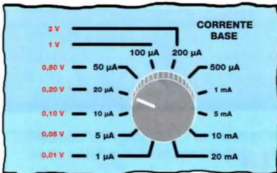
Fig.7 Quando si testano i Fet, la manopola della Corrente di Base fornisce in uscita le Tensioni indicate nella Tabella N.1.
