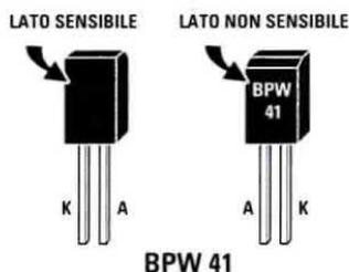
**Fig.16** Poichè i due terminali A-K del diodo ricevente utilizzato in questo montaggio hanno la medesima lunghezza, per individuare il lato sensibile dovrete verificare su quale di essi è stampigliata la sigla BPW41. Il lato "sensibile" ai raggi infrarossi è quello in cui **NON APPARE** nessuna sigla. Questo lato andrà rivolto verso sinistra (vedi fig.12).
