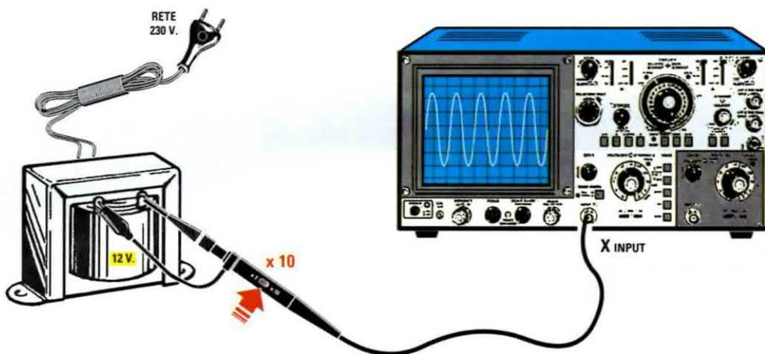
Fig.9 Se misurate la tensione dei 12 volt erogata dal trasformatore di fig.8 con un oscilloscopio, noterete che l'ampiezza del segnale raggiungerà un valore di 33,9 volt perchè questo strumento legge il valore dei Volt Picco/Picco che si ricava moltiplicando il valore dei Volt Efficaci x 2,828 (vedi fig.16). Per evitare errori di lettura controllate sempre se il deviatore presente nella sonda è posizionato sulla portata x1 o x10.
