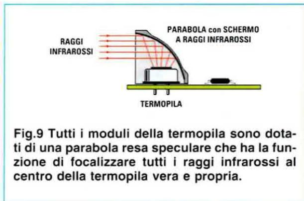
**Fig.9 Tutti i moduli della termopila sono dotati di una parabola resa speculare che ha la funzione di focalizzare tutti i raggi infrarossi al centro della termopila vera e propria.**
