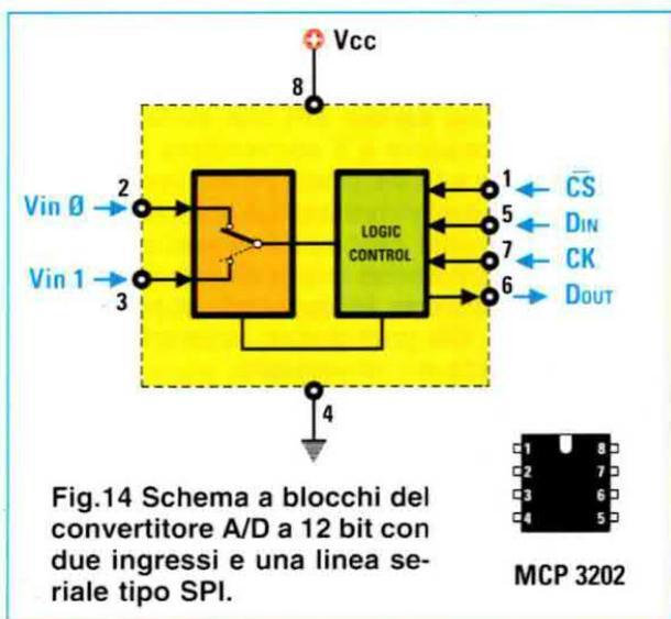
Fig.14 Schema a blocchi del convertitore A/D a 12 bit con due ingressi e una linea seriale tipo SPI.
