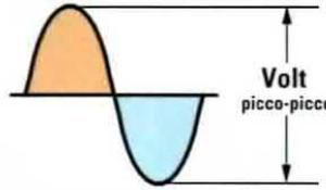
Fig.16 I Volt efficaci di un'onda Sinusoidale si ottengono dividendo per 2,828 i Volt P/P.
