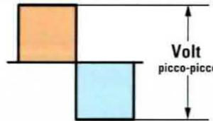
Fig.18 I Volt efficaci di un'onda Quadra si ottengono dividendo per 2 i Volt Picco/Picco.
