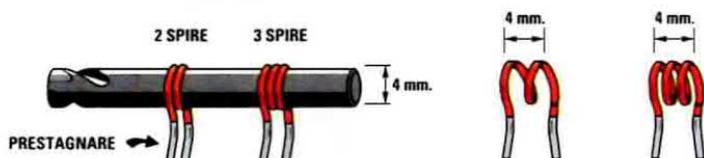
Fig.14 Per la gamma 280-480 MHz dovreste avvolgere 2 spire per L2-L4 e 3 spire per L3-L5 su un supporto del diametro di 4 mm.
