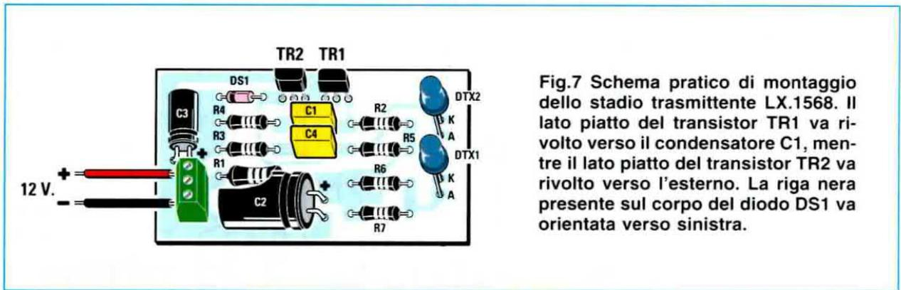
Fig.7 Schema pratico di montaggio dello stadio trasmettente LX.1568. Il lato piatto del transistor TR1 va rivolto verso il condensatore C1, mentre il lato piatto del transistor TR2 va rivolto verso l'esterno. La riga nera presente sul corpo del diodo DS1 va orientata verso sinistra.
