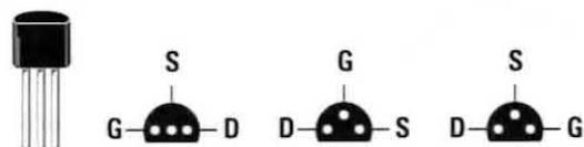
Fig.3 Le connessioni G-S-D, viste da sotto, di un Fet con corpo plastico. Poichè ciascun Fet presenta questi terminali disposti in modo diverso, in ogni schema elettrico dovrebbe apparire la disposizione G-S-D del Fet che è stato utilizzato.
