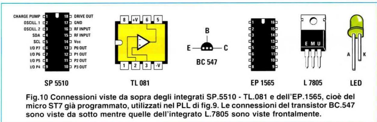
Fig.10 Connessioni viste da sopra degli integrati SP.5510 - TL.081 e dell'EP.1565, cioè del micro ST7 già programmato, utilizzati nel PLL di fig.9. Le connessioni del transistor BC.547 sono viste da sotto mentre quelle dell'integrato L.7805 sono viste frontalmente.
