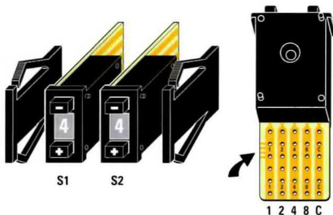
Fig.8 Dal corpo dei Commutatori Binari esce un ritaglio di circuito stampato provvisto di 5 piste in rame sul quale dovrete collegare i fili contrassegnati 1-2-4-8-C che escono dal circuito del PLL di fig.7. I fili indicati "verso S1" vanno collegati al commutatore di sinistra e i fili indicati "verso S2" vanno collegati al commutatore di destra. Sulle sottili piste in rame di questi Commutatori Binari sono incisi, con caratteri appena visibili, i numeri 1-2-4-8 e la lettera C.
