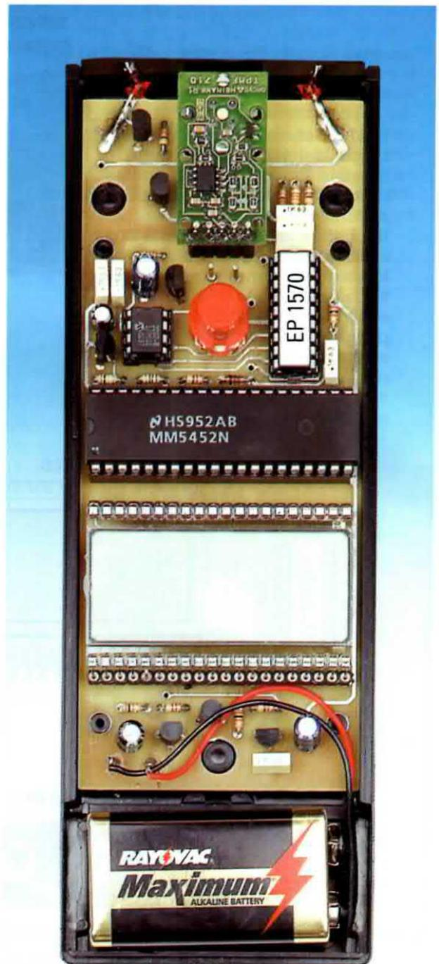
**Fig.19** Foto del termometro dentro al mobile. Come vedete siamo riusciti a fare uno schema compatto anche senza usare componenti in SMD. Chiunque sarà così in grado di montarlo senza difficoltà. Dentro il mobile opportunamente forato troverà posto anche una normale pila da 9 volt per l'alimentazione generale.
