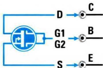
Fig.22 Per controllare un Mosfet dovreste solo collegare insieme il Gate 1 con il Gate 2 e poi applicarli sulla boccia B del Tracciacurve.
