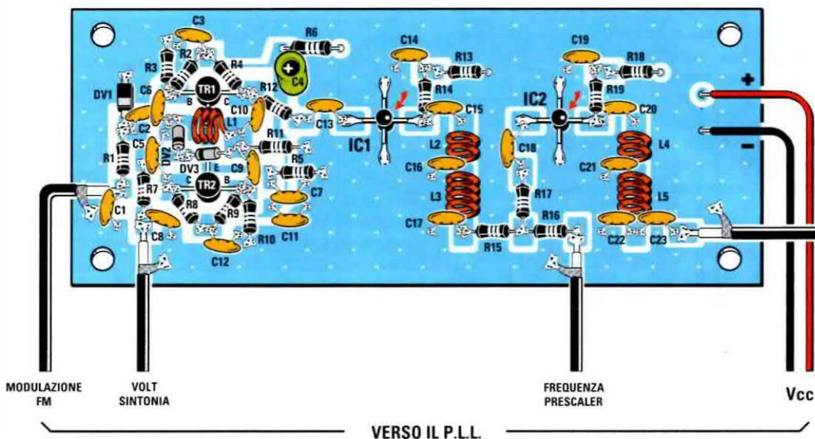
Fig.17 Schema pratico di montaggio dello stadio VCO. Vi ricordiamo che in funzione della gamma di lavoro che sceglierete, dovrete utilizzare per le bobine e i condensatori i valori riportati nella Tabella N.1 e nella Tabella N.2. I cavetti coassiali visibili in basso vanno collegati al circuito stampato del PLL come evidenziato in fig.20.
