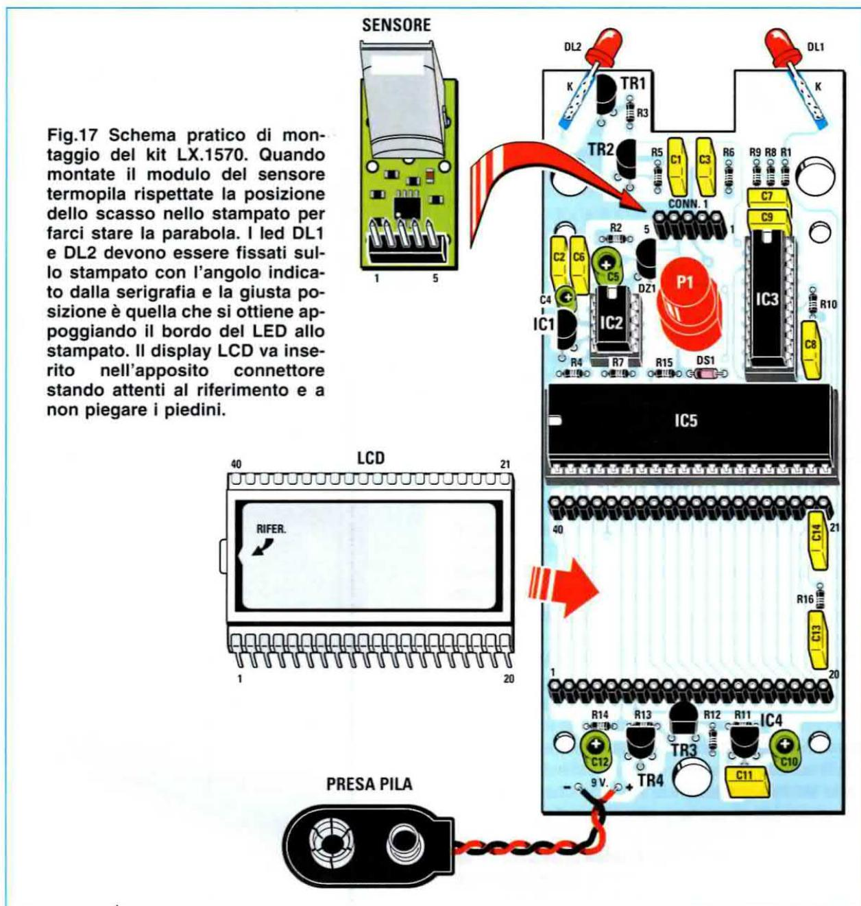
Fig.17 Schema pratico di montaggio del kit LX.1570. Quando montate il modulo del sensore termopila rispettate la posizione dello scasso nello stampato per farci stare la parabola. I led DL1 e DL2 devono essere fissati sullo stampato con l'angolo indicato dalla serigrafia e la giusta posizione è quella che si ottiene appoggiando il bordo del LED allo stampato. Il display LCD va inserito nell'apposito connettore stando attenti al riferimento e a non piegare i piedini.
