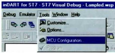
Fig.2 Per aprire la finestra visibile in fig.4, cliccate sul comando MCU Configuration... che si trova nel menu Tools.
