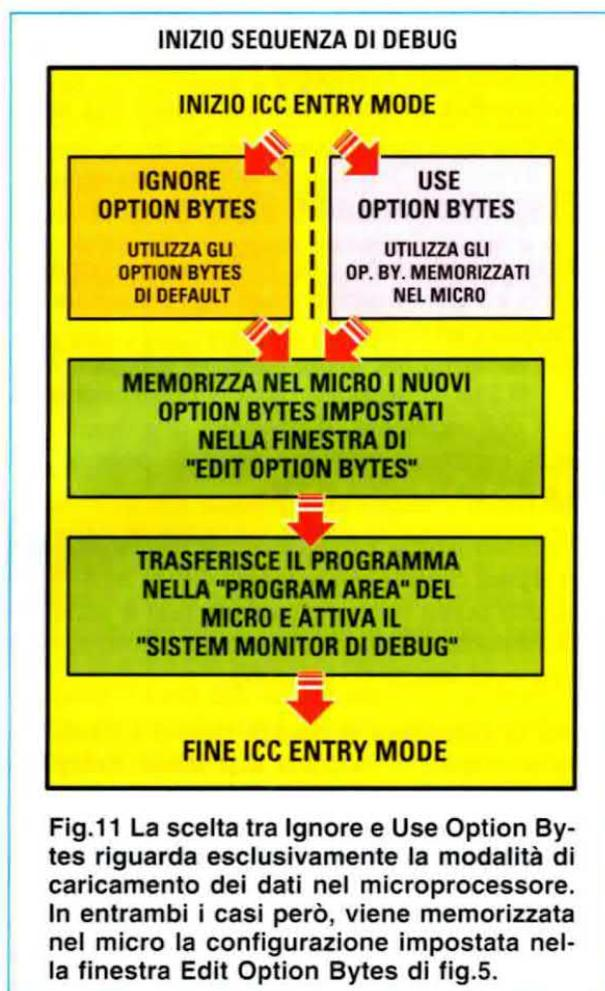
**Fig.11** La scelta tra Ignore e Use Option Bytes riguarda esclusivamente la modalità di caricamento dei dati nel microprocessore. In entrambi i casi però, viene memorizzata nel micro la configurazione impostata nella finestra Edit Option Bytes di fig.5.
