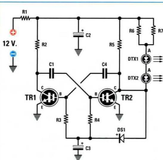
Fig.2 Schema elettrico dello stadio trasmettente in grado di generare degli impulsi ad onda quadra a 1.000 Hz (vedi fig.3). Il terminale Anodo dei due diodi all'infrarosso va rivolto verso i 12 volt positivi.
