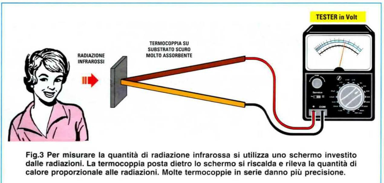
Fig.3 Per misurare la quantità di radiazione infrarossa si utilizza uno schermo investito dalle radiazioni. La termocoppia posta dietro lo schermo si riscalda e rileva la quantità di calore proporzionale alle radiazioni. Molte termocoppie in serie danno più precisione.
