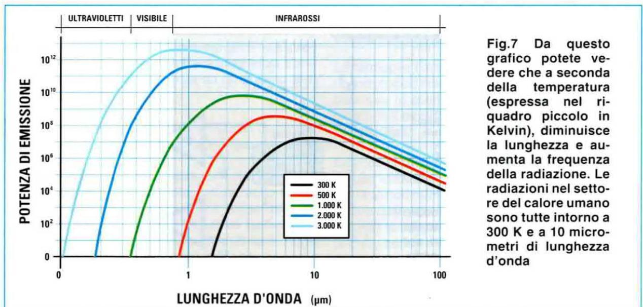
Fig.7 Da questo grafico potete vedere che a seconda della temperatura (espressa nel riquadro piccolo in Kelvin), diminuisce la lunghezza e aumenta la frequenza della radiazione. Le radiazioni nel settore del calore umano sono tutte intorno a 300 K e a 10 micrometri di lunghezza d'onda
