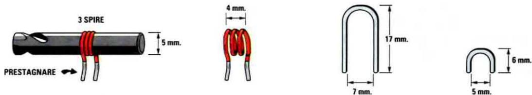
Fig.12 Per realizzare un VCO sulla gamma dei 180-310 MHz dovreste avvolgere 3 spire su un diametro di 5 mm. Per la gamma dei 280-480 MHz basta una spira U lunga 17 mm circa, mentre per la gamma dei 400-730 MHz una piccola spira a U lunga 6 mm.
