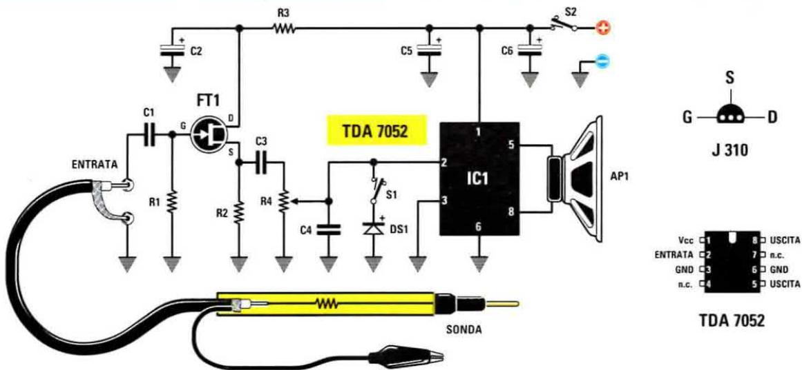
Fig.1 Schema elettrico del Signal-Tracer che utilizza come stadio finale l'integrato TDA.7052. Le connessioni del TDA.7052 sono viste da sopra e quelle del fet J.310 da sotto.
