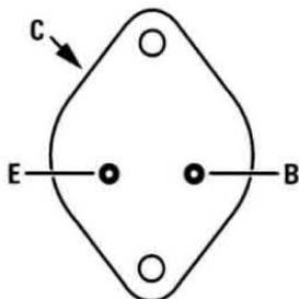
Fig.3 A sinistra, le connessioni del transistor di potenza siglato 2N.3055 viste da sotto e, a destra, quelle di un transistor di potenza con corpo plastico più quelle di vari transistor pilota (TR2), sia plastici che metallici, viste da sotto.
