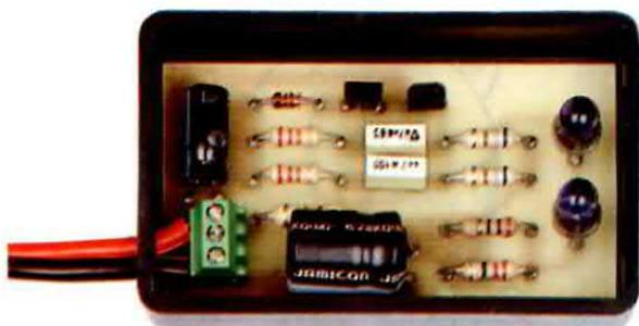
Fig.11 Sul coperchio del contenitore plastico di fig.10 dovrete praticare due fori per far uscire la testa dei diodi CQX.89.
