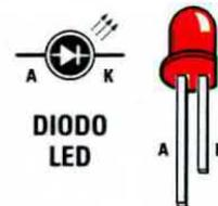
Fig.2 Negli alimentatori che utilizzano integrati della serie 79, il terminale Catodo del diodo led ed il terminale negativo dell'elettrolitico C3 vanno rivolti verso il terminale M di IC1.
