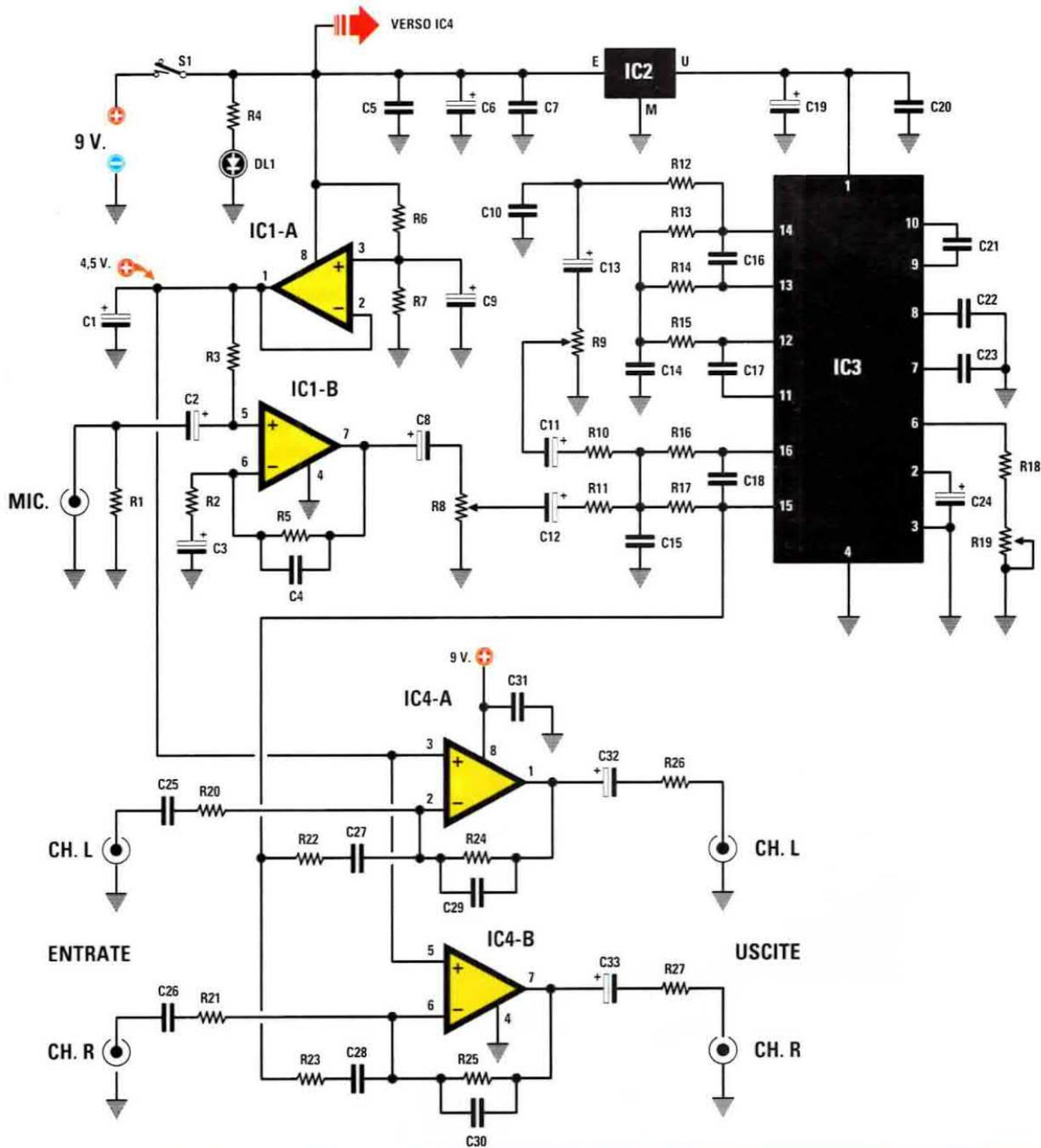
Fig.2 Sopra, schema elettrico del Karaoke in cui è ben visibile a destra il processore HT.8970 della Holtek (vedi IC3), che serve per generare l'effetto Eco e di cui, qui a destra, è riprodotto lo schema a blocchi interno.
