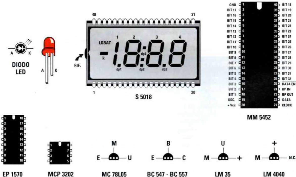
Fig.12 Veduta della piedinatura dei vari componenti usati in questo progetto.
