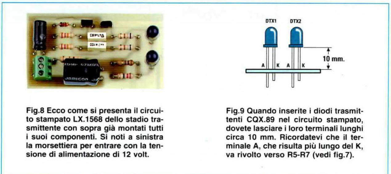
Fig.8 Ecco come si presenta il circuito stampato LX.1568 dello stadio trasmettente con sopra già montati tutti i suoi componenti. Si noti a sinistra la morsettiere per entrare con la tensione di alimentazione di 12 volt.
