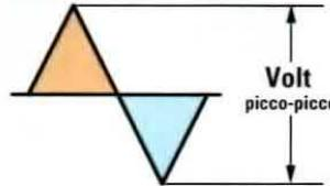
Fig.17 I Volt efficaci di un'onda Triangolare si ottengono dividendo per 3,464 i Volt P/P.
