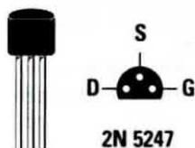
Fig.14 I tre terminali D-S-G del Fet 2N.5247 visti da sotto.
