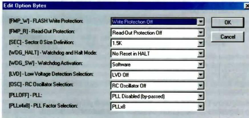
Fig.5 La finestra Edit riproduce la configurazione dei registri Option Bytes per il progetto lamped.wsp. Analizzando ad una ad una tutte le opzioni, imparerete a stabilire le modalità di gestione di questi registri.
