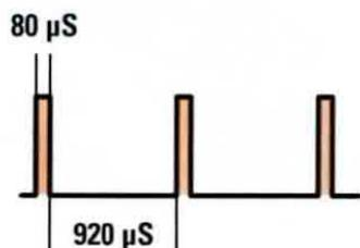
Fig.3 Lo stadio trasmettente riprodotto in fig.2 eccita i diodi trasmettenti per un tempo di 80 microsecondi con degli impulsi idonei a far loro assorbire una corrente di circa 400 milliamper.
