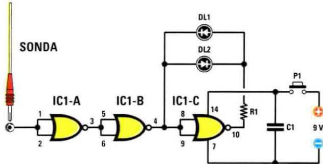
Fig.1 Schema elettrico del rivelatore di segnali RF e, sotto, elenco dei componenti.
