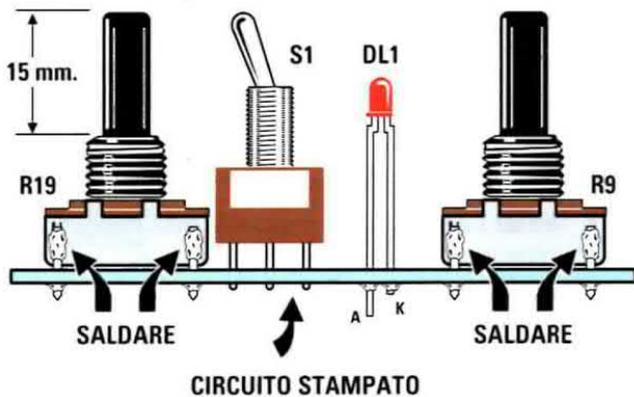
Fig.5 Quando monterete i due potenziometri R9 ed R19 vi raccomandiamo di mantenere i perni su una lunghezza di 15 mm, per consentire alle manopole di fuoriuscire dai fori predisposti sulla mascherina. Per lo stesso motivo, anche nel montaggio del potenziometro R8, del diodo led e dell'interruttore S1 dovete tenere presente l'altezza del mobile.
