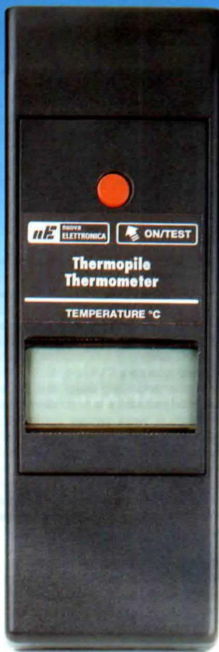
**Fig.20** Foto del termometro dentro il suo mobile e completato con l'adesivo che vi forniamo. In un unico pulsante siamo riusciti a concentrare tutti i comandi: premendolo la prima volta si accende e visualizza la temperatura ambiente, ripremendolo e puntando i LED sulla pelle, ci dà se rilasciato, la temperatura della pelle.
