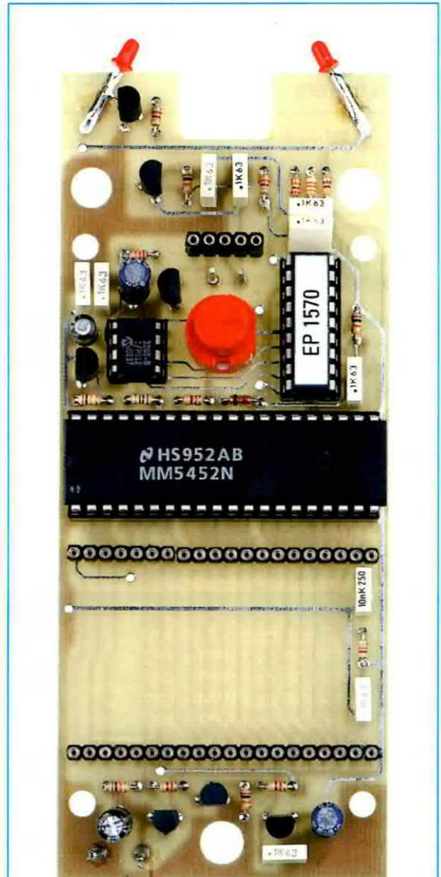
Fig.16 Foto del circuito stampato con sopra montati tutti i componenti, tranne il circuito con il sensore termopila e il display.
