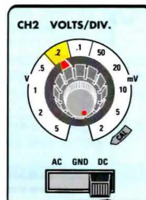
Fig.15 Tenendo la manopola della Corrente di Base sulla posizione 20  $\mu$ A che corrisponde ad un tensione di Gate di 0,2 volt (vedi fig.7) e la manopola CH2 dell'oscilloscopio sulla posizione 0,2 Volts/div., sullo schermo potrebbero apparire delle tracce molto ravvicinate. Per distanziarle basta ruotare la manopola CH2 su una portata inferiore (vedi fig.16-17).
