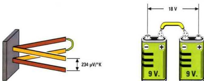
**Fig.1** Le termocoppie se riscaldate sono dei veri e propri generatori, come le pile. Come le pile per poter elevare la tensione si possono collegare in serie, allo stesso modo le termocoppie si possono collegare in serie per alzare il loro segnale.
