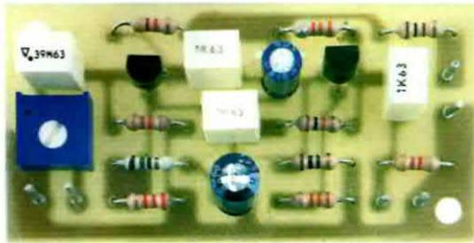
Fig.1 Foto del preamplificatore montato.
