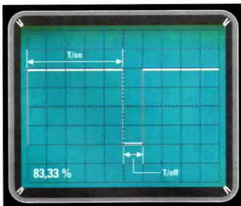
Fig.7 Poichè in questo secondo esempio notiamo che il segnale T/on copre 5 quadretti e il segnale T/off copre 1 quadretto, la percentuale sarà pari a:
