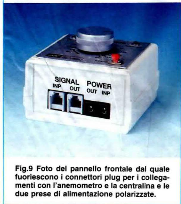
**Fig.9** Foto del pannello frontale dal quale fuoriescono i connettori plug per i collegamenti con l'anemometro e la centralina e le due prese di alimentazione polarizzate.
