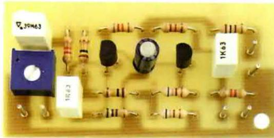
Fig.1 Foto del preamplificatore montato.
