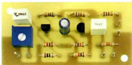
Fig.1 Foto del preamplificatore montato.
