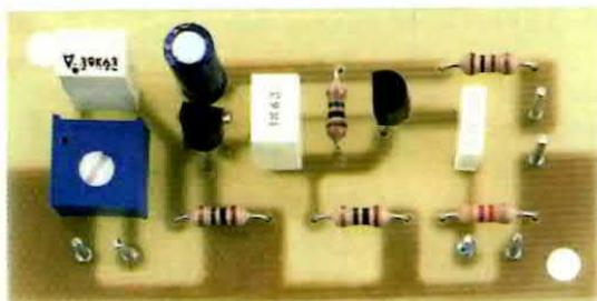
Fig.1 Foto del preamplificatore montato.
