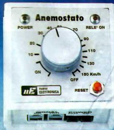
Fig.7 Foto del contenitore che racchiude il nostro anemostato. Sul coperchio dovete montare il potenziometro, il pulsante e le ghiera cromate per i due diodi led.
