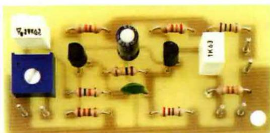
Fig.1 Foto del preamplificatore montato.
