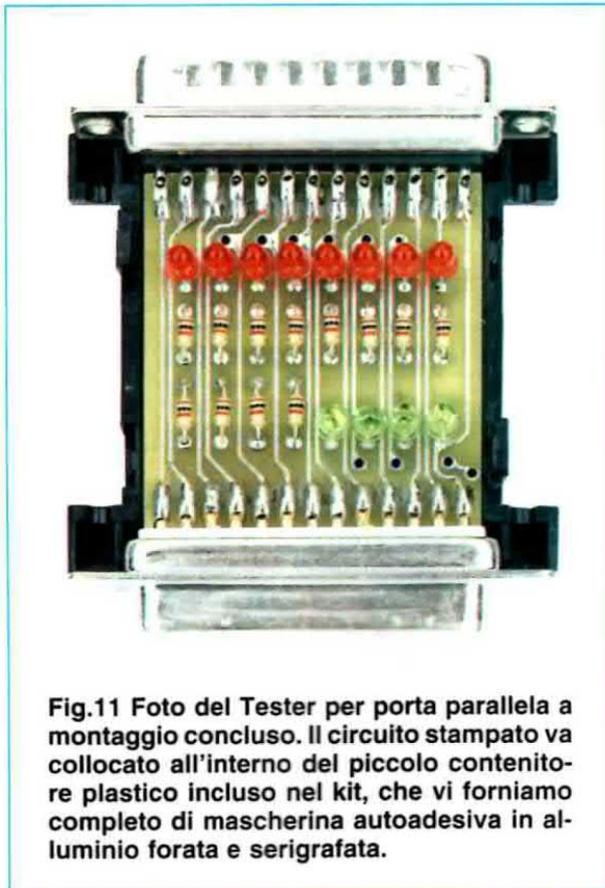
Fig.11 Foto del Tester per porta parallela a montaggio concluso. Il circuito stampato va collocato all'interno del piccolo contenitore plastico incluso nel kit, che vi forniamo completo di mascherina autoadesiva in alluminio forata e serigrafata.
