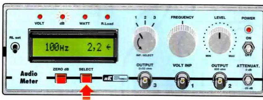
Fig.22 Premendo il pulsante Select per 1 secondo riuscirete a far accendere il Diodo Led dei dB e vedrete così apparire sul Display un numero seguito da una "freccia". Se ora premete il pulsante "Zero dB" per circa 1 secondo, apparirà il valore 0,0 dB.
