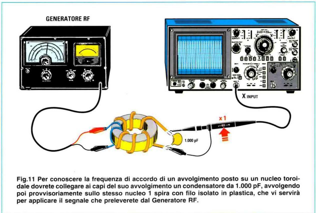
Fig.11 Per conoscere la frequenza di accordo di un avvolgimento posto su un nucleo toroidale dovreste collegare ai capi del suo avvolgimento un condensatore da 1.000 pF, avvolgendo poi provvisoriamente sullo stesso nucleo 1 spira con filo isolato in plastica, che vi servirà per applicare il segnale che preleverete dal Generatore RF.
