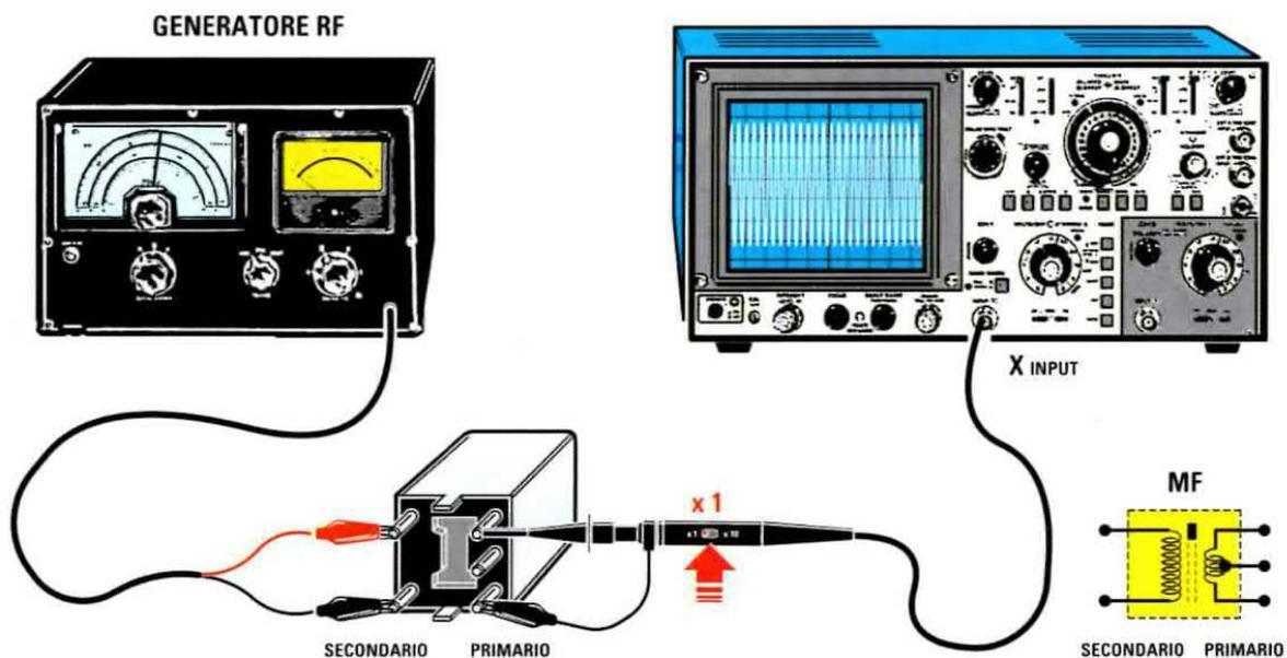
Fig.14 Per conoscere la frequenza di lavoro di una MF basta controllare la disposizione dei terminali che escono dal suo zoccolo. L'avvolgimento Secondario sul quale va applicato il segnale fornito dal Generatore RF ha sempre "2 terminali", mentre l'avvolgimento Primario che va collegato all'Oscilloscopio ha sempre "3 terminali". Su questo avvolgimento non va applicato nessun condensatore essendo questo già presente all'interno dell'impedenza.
