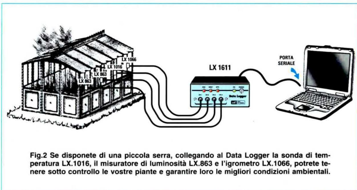
**Fig.2** Se disponete di una piccola serra, collegando al Data Logger la sonda di temperatura LX.1016, il misuratore di luminosità LX.863 e l'igrometro LX.1066, potrete tenere sotto controllo le vostre piante e garantire loro le migliori condizioni ambientali.
