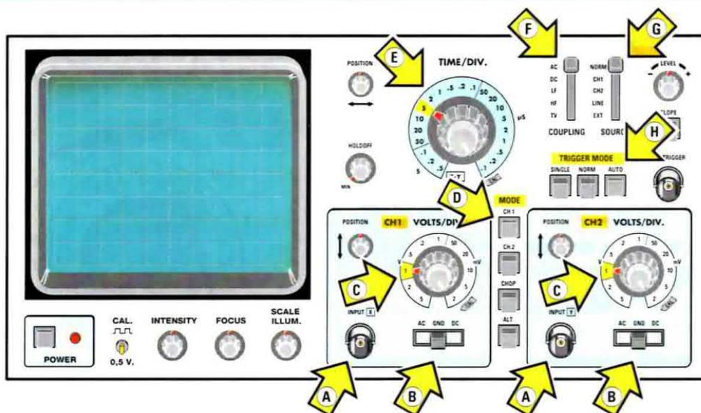
Fig.1 Nella Legenda riportata sopra il titolo sono descritte le funzioni svolte dai comandi presenti sul pannello frontale di un comune oscilloscopio.
