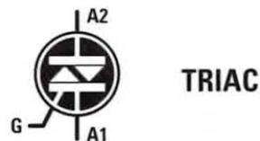
Fig.4 Ecco come si presenta il simbolo grafico di un Diodo **TRIAC**. I terminali che escono dal suo corpo sono chiamati **Gate, Anodo 2, Anodo 1**. Per saperne di più, consultate il nostro volume **Handbook**.
