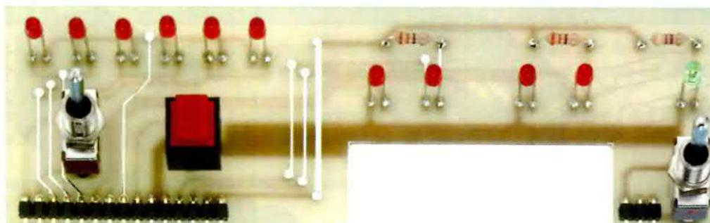
Fig.12 Foto della scheda LX.1610/B con sopra già inseriti tutti i diodi led. Facciamo presente che il diodo DL1 posto sopra il deviatore a levetta di destra è l'unico di colore "verde". Questa scheda viene tenuta bloccata sul pannello frontale del mobile tramite i due dadi presenti nei due deviatori S1-S2.
