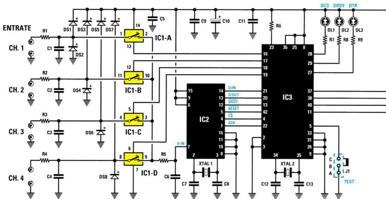
Fig.4 Schema elettrico del Data Logger LX.1611. Il segnale applicato ai 4 ingressi analogici viene inviato ai 4 switch digitali IC1/A-IC1/B-IC1/C-IC1/D, gestiti dal micro-processore ST7, che abilitano il passaggio dei segnali al piedino 7 dell'A/D converter.
