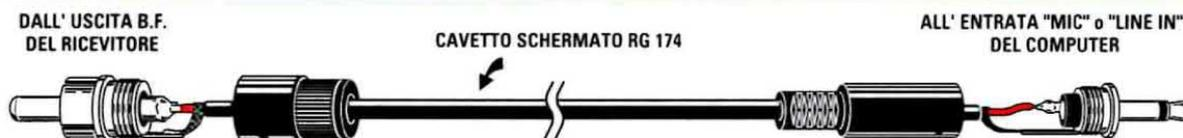
**Fig.2** Per scaricare sul computer le immagini del Meteosat captate dal ricevitore, dovete costruire un cavo audio con un cavetto schermato tipo RG.174, uno spinotto di BF, da collegare al ricevitore, ed uno spinotto jack da 3 mm, da collegare al computer. Il cavo centrale va saldato al centrale degli spinotti e la calza di schermo ai terminali esterni.
