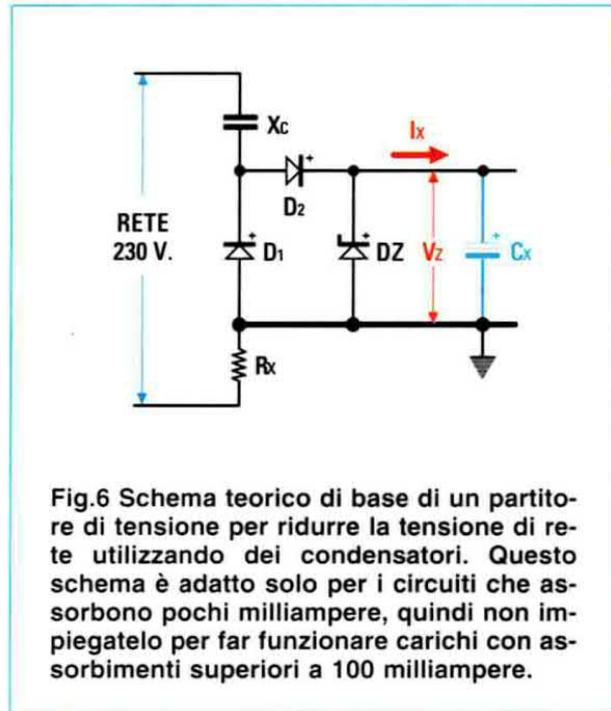
**Fig.6** Schema teorico di base di un partitore di tensione per ridurre la tensione di rete utilizzando dei condensatori. Questo schema è adatto solo per i circuiti che assorbono pochi milliamper, quindi non impiegarlo per far funzionare carichi con assorbimenti superiori a 100 milliamper.
