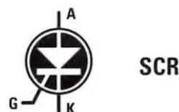
Fig.2 Il simbolo grafico di un **SCR** non può essere confuso con quello di un **PUT** perchè il suo terminale **Gate** esce in basso, in prossimità del terminale **Katodo**. In fig.7 potete vedere come si presentano in pratica un **PUT** e un diodo **SCR**.
