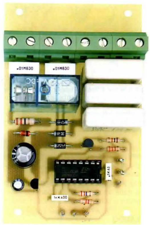
Fig.7 Schema pratico del Timer e foto del circuito a montaggio ultimato. I grossi condensatori C1-C2-C3 formano la reattanza capacitiva  $X_c$ , che provoca la riduzione della tensione da 230 volt a circa 12 volt. Il potenziometro e il deviatore vanno collegati al circuito solo dopo aver collocato quest'ultimo nel mobile plastico (vedi fig.8).
