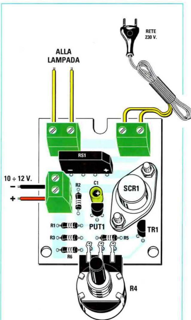
Fig.23 Schema pratico di montaggio del circuito di fig.22. Il ponte raddrizzatore RS1 va collocato sul circuito stampato rivolgendolo al terminale + verso destra.
