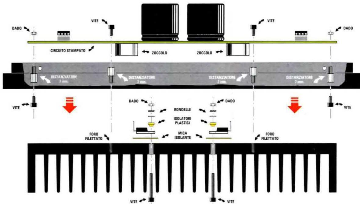
**Fig.13** Dopo aver fissato i quattro Mosfet sulla lunga aletta di raffreddamento dovreste fissare il coperchio del mobile metallico alla stessa aletta utilizzando i distanziatori metallici di forma esagonale che troverete nel kit. Questi distanziatori metallici vi serviranno anche per fissare il coperchio al circuito stampato (vedi figg.14-15).
