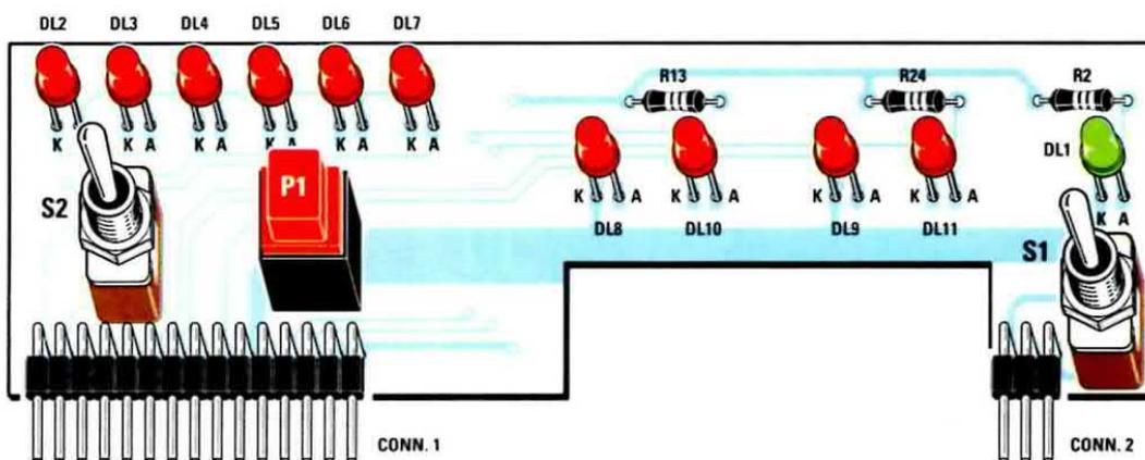
Fig.10 Schema pratico di montaggio della scheda LX.1610/B utilizzata per ricevere i due connettori Conn.1 e Conn.2, i due deviatori a levetta S2-S1, il pulsante P1 e gli 11 diodi led. Per fissare alla medesima altezza tutti i diodi led, vi consigliamo di leggere il testo e di guardare anche la fig.13 per quanto riguarda i due terminali A-K.
