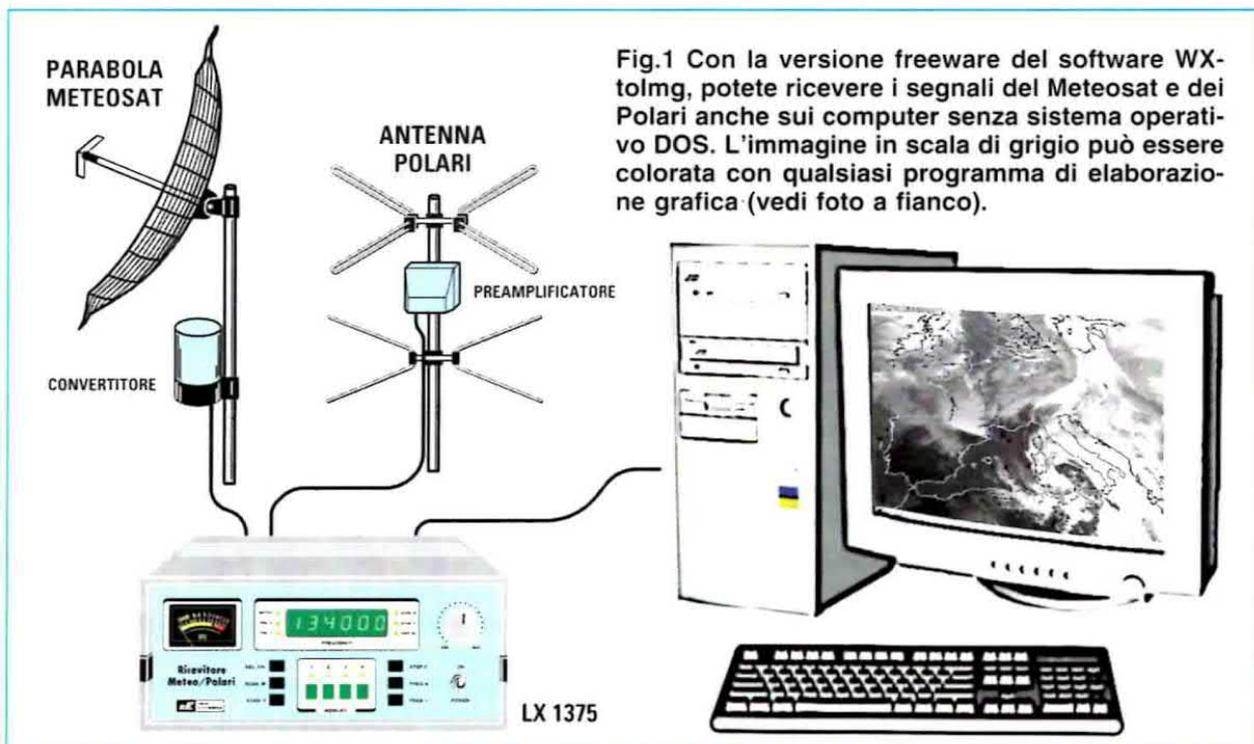
Fig.1 Con la versione freeware del software **WX-tolmg**, potete ricevere i segnali del **Meteosat** e dei **Polari** anche sui computer senza sistema operativo **DOS**. L'immagine in scala di grigio può essere colorata con qualsiasi programma di elaborazione grafica (vedi foto a fianco).
