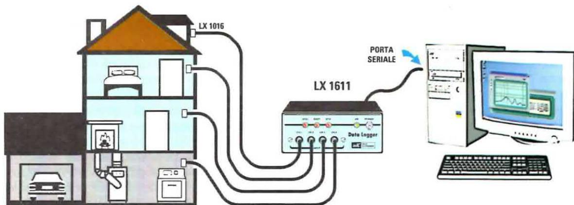
Fig.1 Collegando all'interno di ciascun locale della vostra abitazione la nostra sonda di temperatura LX.1016 potrete divertirvi ad osservare come varia nel tempo la temperatura ambiente al variare della temperatura esterna. Sul monitor del vostro personal computer potrete inoltre visualizzare il relativo grafico. In figura sono rappresentati i collegamenti al Data Logger e alla porta seriale del PC.
