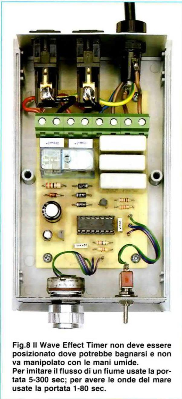
**Fig.8 Il Wave Effect Timer non deve essere posizionato dove potrebbe bagnarsi e non va manipolato con le mani umide. Per imitare il flusso di un fiume usate la portata 5-300 sec; per avere le onde del mare usate la portata 1-80 sec.**
