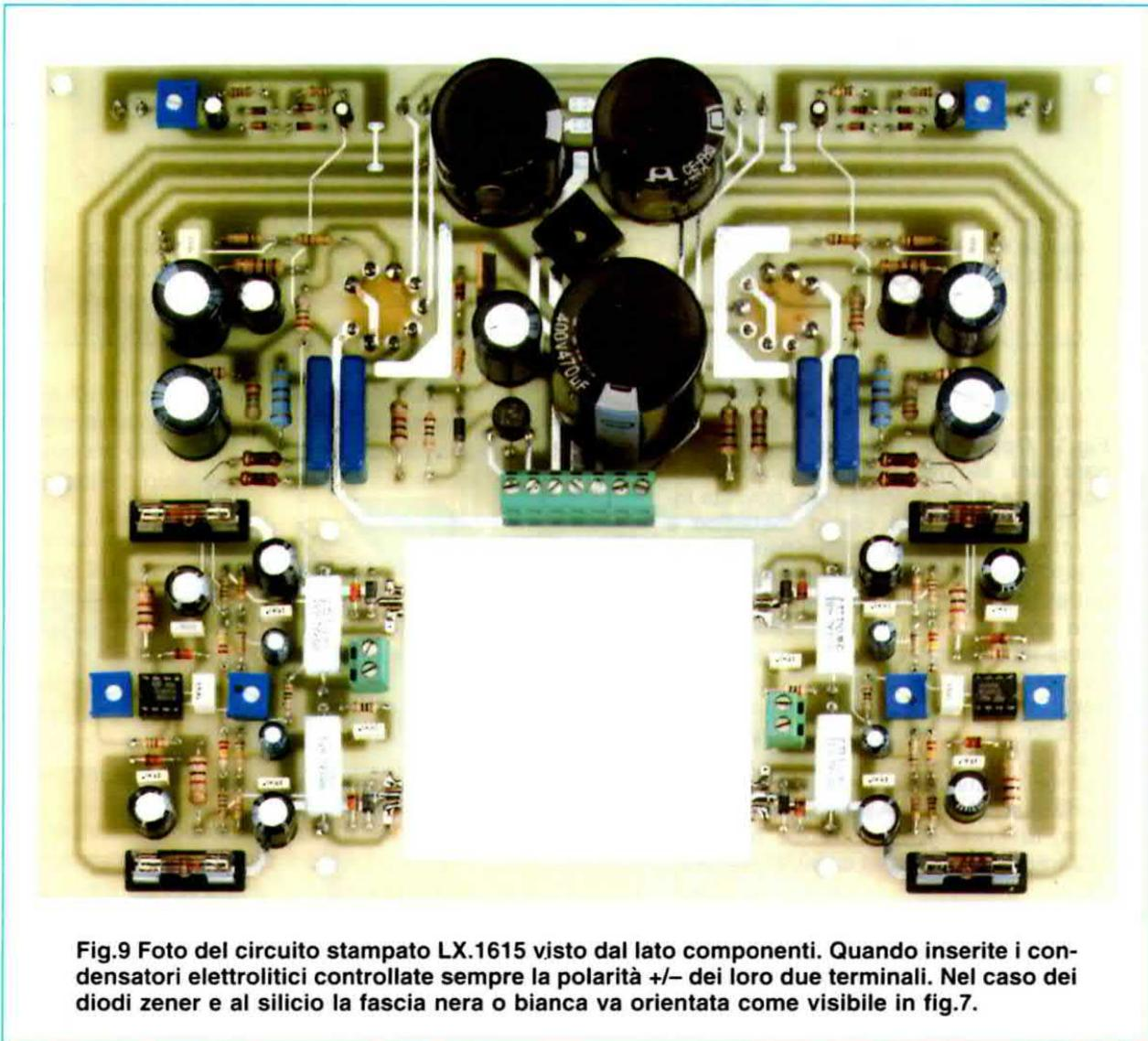
Fig.9 Foto del circuito stampato LX.1615 visto dal lato componenti. Quando inserite i condensatori elettrolitici controllate sempre la polarità +/- dei loro due terminali. Nel caso dei diodi zener e al silicio la fascia nera o bianca va orientata come visibile in fig.7.
