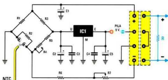
Il segnale da inviare al Data Logger andrà prelevato ai capi del connettore siglati + e -, non prima di avere collegato ai suoi capi una resistenza del valore di circa 10.000 ohm.
