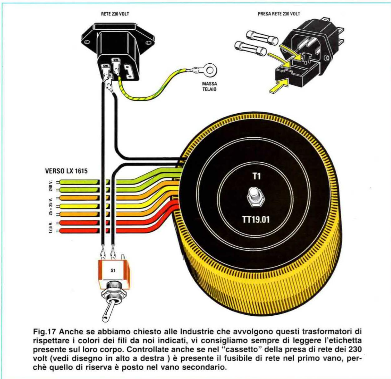
Fig.17 Anche se abbiamo chiesto alle Industrie che avvolgono questi trasformatori di rispettare i colori dei fili da noi indicati, vi consigliamo sempre di leggere l'etichetta presente sul loro corpo. Controllate anche se nel "cassetto" della presa di rete dei 230 volt (vedi disegno in alto a destra) è presente il fusibile di rete nel primo vano, perchè quello di riserva è posto nel vano secondario.
