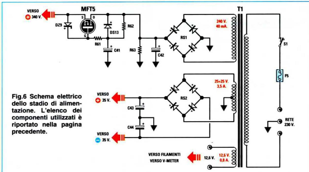
Fig.6 Schema elettrico dello stadio di alimentazione. L'elenco dei componenti utilizzati è riportato nella pagina precedente.
