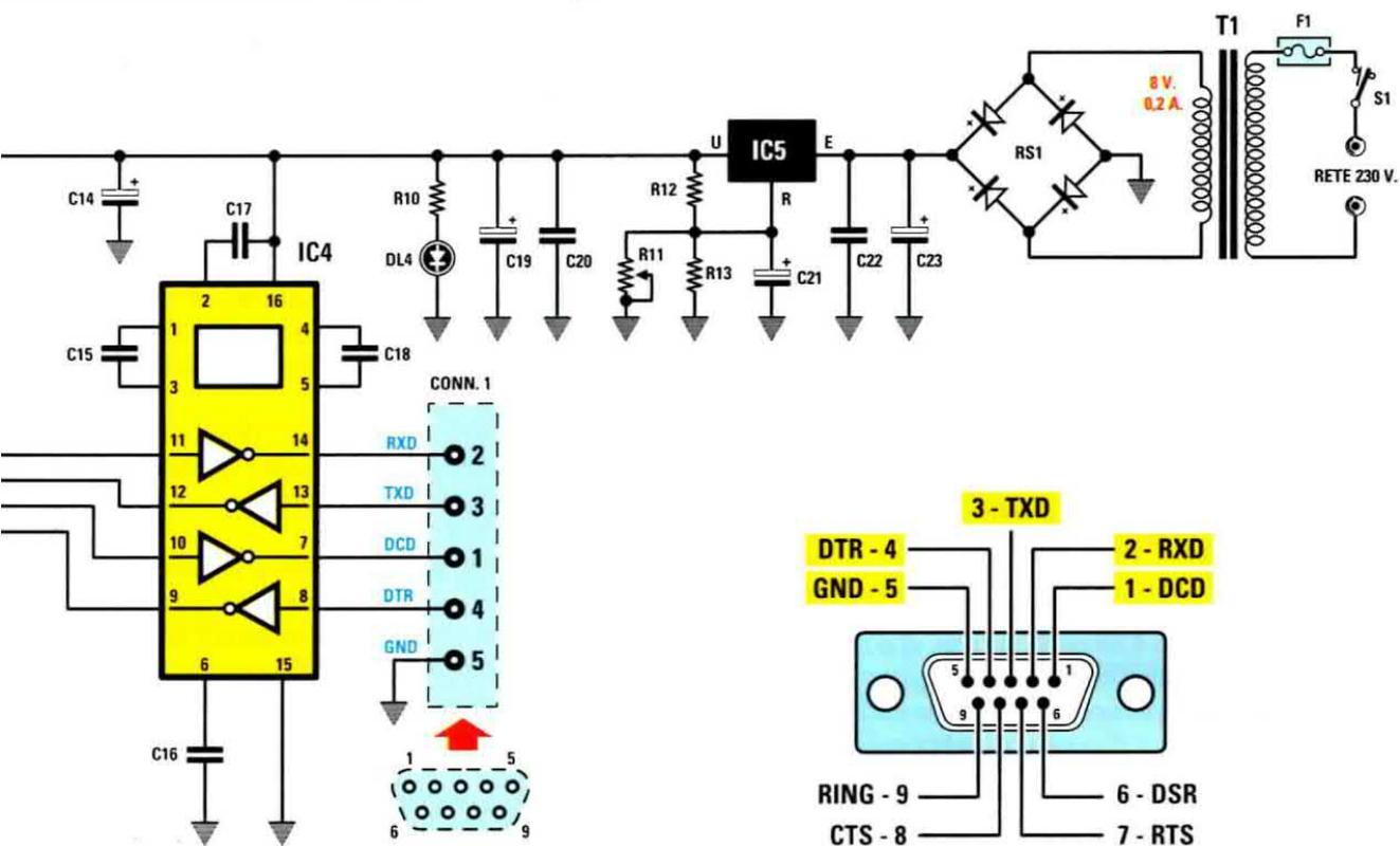
Fig.6 L'integrato IC4 è un convertitore di livelli AD232, e ha la funzione di trasformare i livelli di tensione di 5 volt del segnale TTL nei +/- 12 volt caratteristici della linea seriale RS232. I segnali in uscita vengono poi inviati al connettore femmina a 9 poli visibile in figura.
