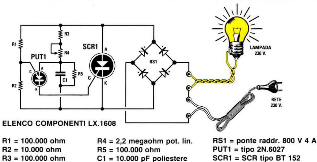
Fig.15 Per realizzare un Varilight in grado di alimentare la lampada con la massima tensione dei 230 Volt, occorre aggiungere al circuito un Ponte raddrizzatore (vedi RS1) in modo da ottenere una Doppia Semionda positiva con una frequenza di 100 Hertz.
