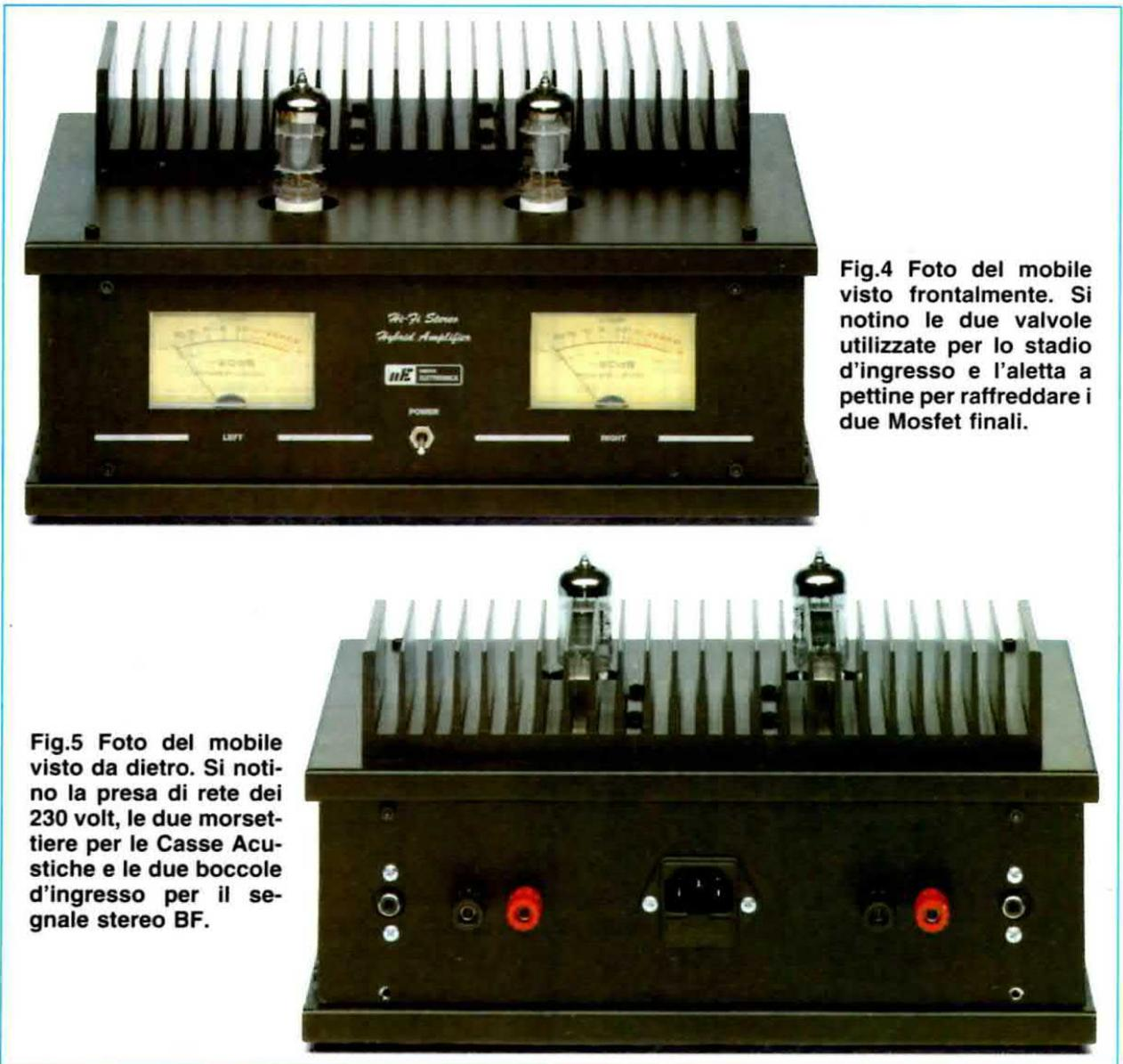
Fig.4 Foto del mobile visto frontalmente. Si notino le due valvole utilizzate per lo stadio d'ingresso e l'aletta a pettine per raffreddare i due Mosfet finali.
