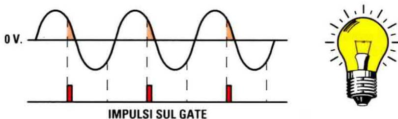
Fig.10 Ruotando il potenziometro R4 per la sua massima resistenza, gli impulsi che escono dal terminale K del PUT andranno ad eccitare l'SCR quando le semionde positive stanno per raggiungere gli 0 Volt, quindi la lampada si accenderà debolmente.
