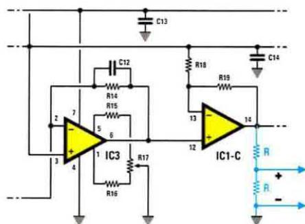
Poiché il fonometro genera una tensione compresa tra 3 e 6 volt, per rimanere nell'intervallo di lettura del Data Logger (0-5 volt), collegate in uscita un partitore formato da 2 resistenze da 10.000 ohm.
