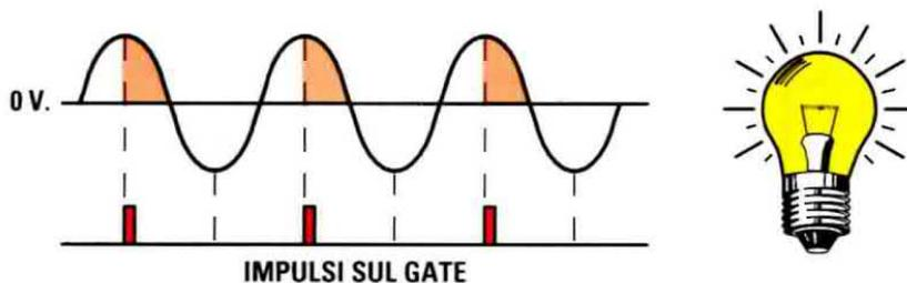
Fig.11 Ruotando il potenziometro R4 a metà corsa, gli impulsi che escono dal terminale K del PUT andranno ad eccitare l'SCR quando le semionde positive avranno raggiunto metà del loro percorso, quindi la lampada si accenderà con una media intensità.
