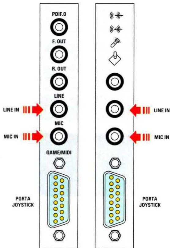
**Fig.3** Lo spinotto jack da 3 mm va inserito nella presa Line In o Mic del computer. Come spiegato nell'articolo, la regolazione dell'audio va eseguita sul controllo del volume dell'entrata scelta (vedi fig.19).
