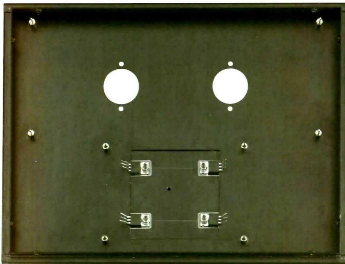
**Fig.12** Dopo aver fissato i quattro Mosfet sull'aletta di raffreddamento facendo attenzione a non confondere gli IRF.520 siglati MFT1-MFT3 con i complementari IRF.9530 siglati MFT2-MFT4 (vedi fig.7), potrete fissare la lunga aletta di raffreddamento, a forma di pettine, sul pannello superiore del mobile metallico (vedi figg.13-14).
