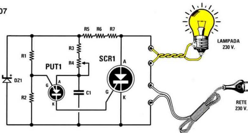
Fig.9 Per ottenere un Varilight, cioè un circuito in grado di variare la luminosità di una lampada a filamento, potrete realizzare questo circuito che utilizza un PUT e un SCR. In fig.13 è riprodotto il disegno pratico di montaggio. Poiché l'SCR si eccita solo sulle semionde positive, la lampada verrà alimentata con una tensione max di soli 115 Volt.
