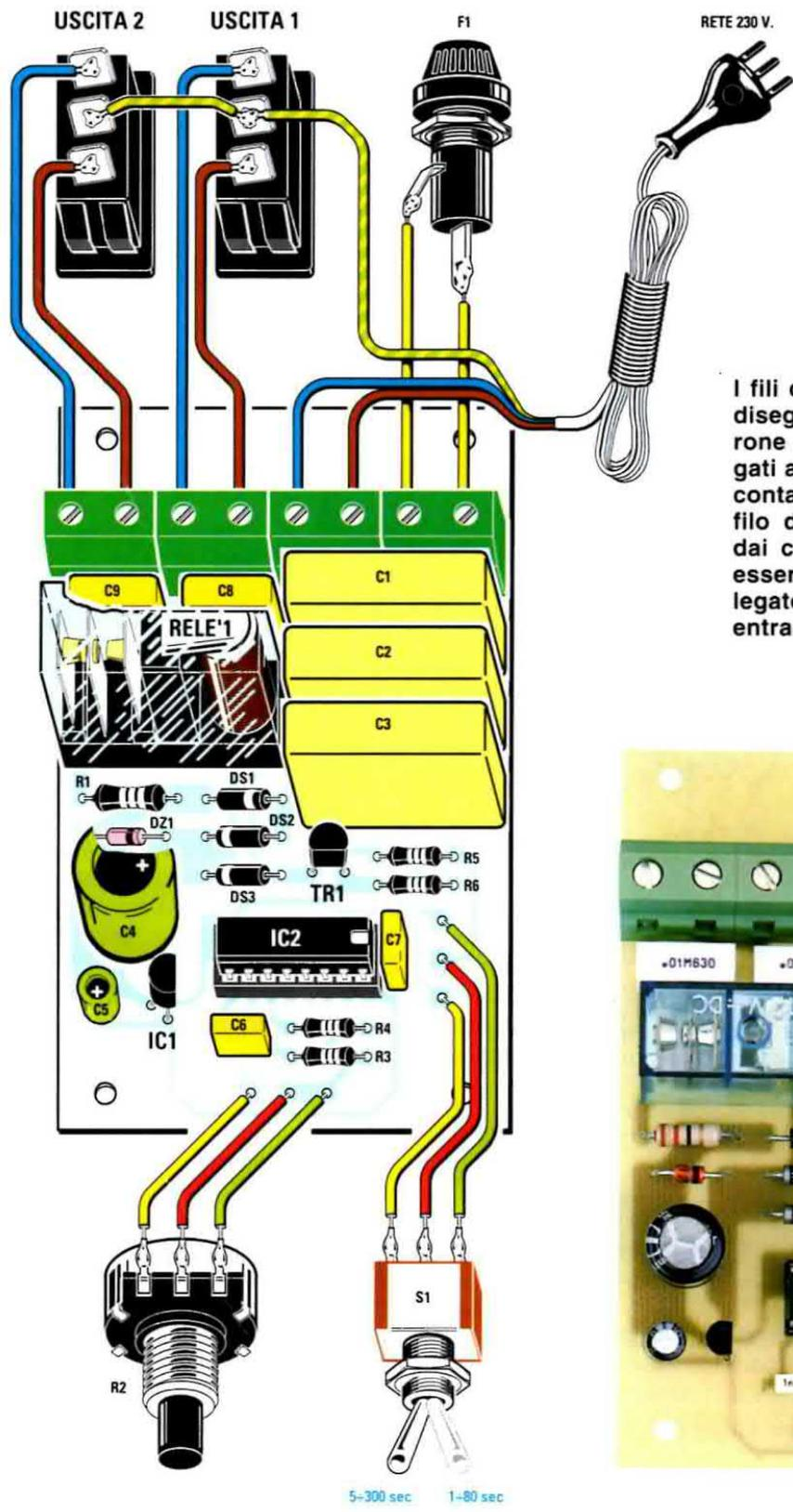
I fili del cavo di rete che nel disegno sono colorati in marrone e azzurro, vanno collegati alla seconda morsetteria contando da destra, mentre il filo di terra, contraddistinto dai colori giallo-verde, deve essere necessariamente collegato al terminale centrale di entrambe le prese d'uscita.
