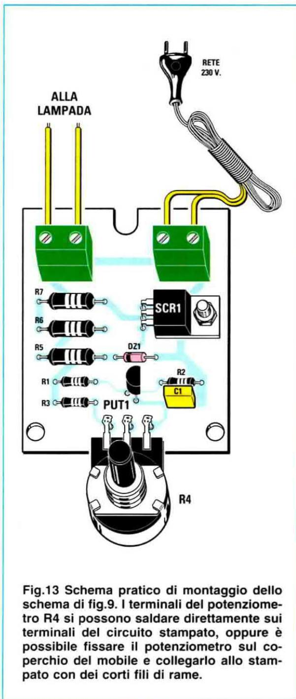
Fig.13 Schema pratico di montaggio dello schema di fig.9. I terminali del potenziometro **R4** si possono saldare direttamente sui terminali del circuito stampato, oppure è possibile fissare il potenziometro sul coperchio del mobile e collegarlo allo stampato con dei corti fili di rame.
