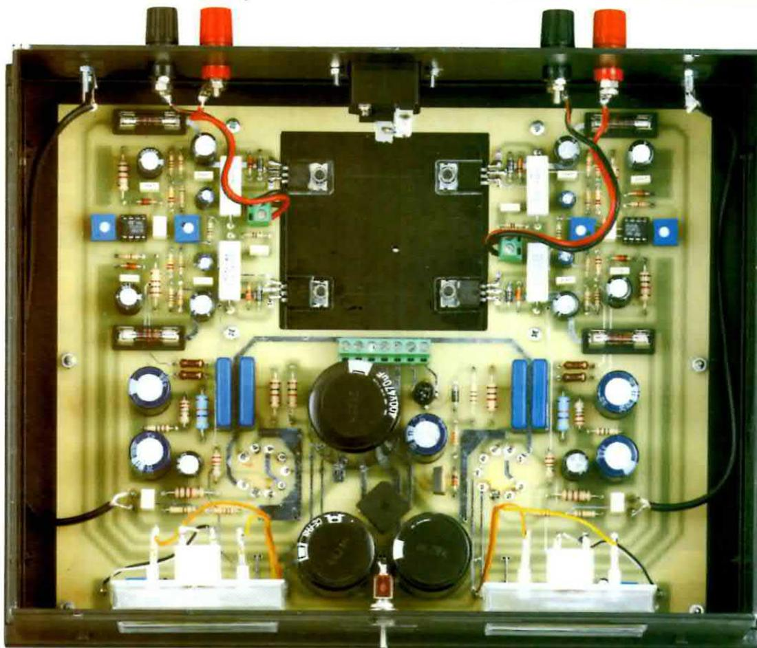
Fig.15 Foto vista da sopra dell'amplificatore Stereo in grado di erogare una potenza di ben 55+55 Watt RMS. Prima di fissare sul pannello posteriore le morsettiere per le Casse Acustiche, dovrete ricordarvi di togliere dal loro corpo la rondella isolante che andrà poi posta all'interno del mobile come visibile in questo disegno.
