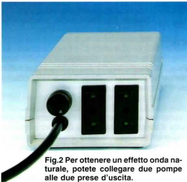
Fig.2 Per ottenere un effetto onda naturale, potete collegare due pompe alle due prese d'uscita.
