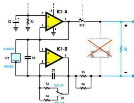
In questo caso, il segnale da inviare al Data Logger va prelevato ai capi dello strumento di misura dopo averlo scollegato e sostituito con una resistenza del valore di 20.000 ohm.
