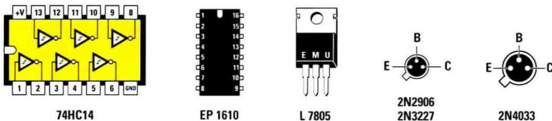
Fig.13 Connessioni degli integrati viste da "sopra" e dei transistor viste invece da "sotto". Per quanto riguarda i diodi led facciamo presente che il terminale più lungo è l'Anodo (A) e il più corto è il Catodo (K). Guardando la fig.10 noterete che il terminale più "lungo" va rivolto verso destra.
