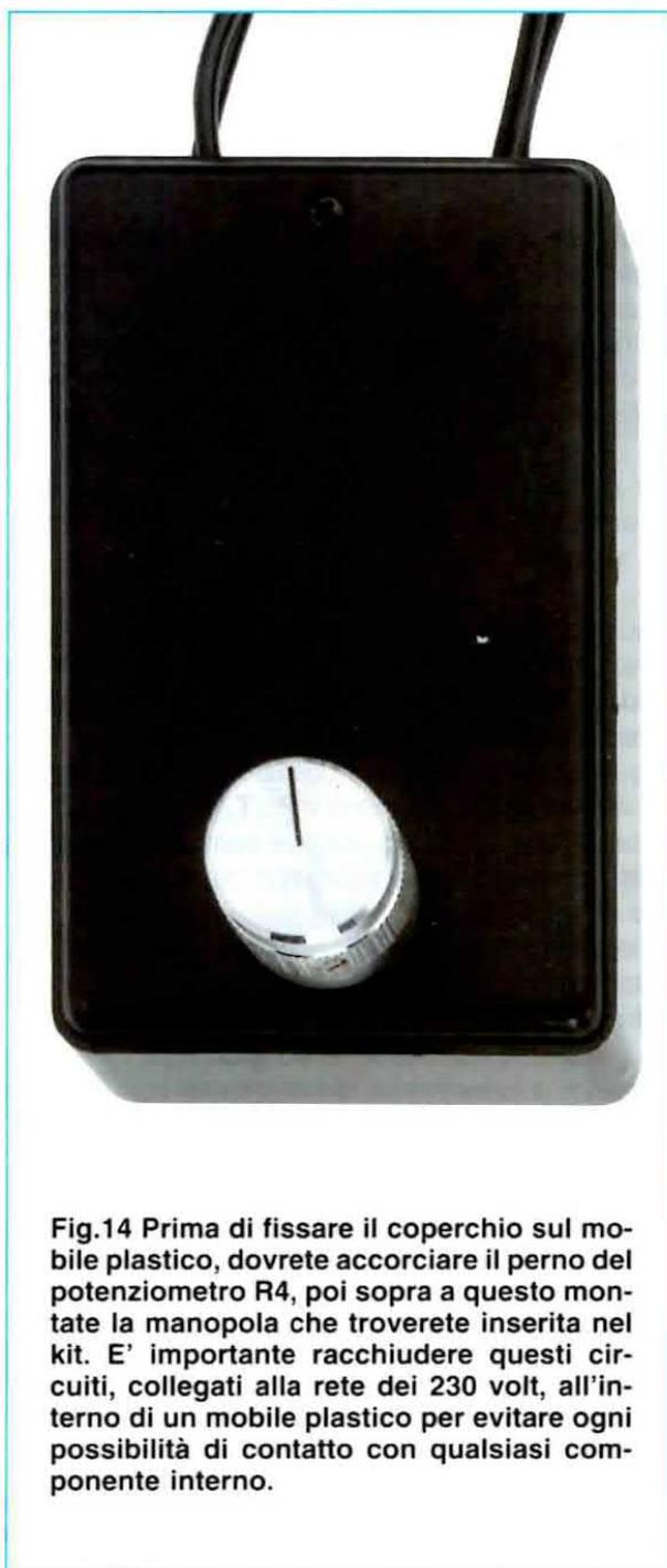
**Fig.14** Prima di fissare il coperchio sul mobile plastico, dovrete accorciare il perno del potenziometro **R4**, poi sopra a questo montate la manopola che troverete inserita nel kit. E' importante racchiudere questi circuiti, collegati alla rete dei **230 volt**, all'interno di un mobile plastico per evitare ogni possibilità di contatto con qualsiasi componente interno.
