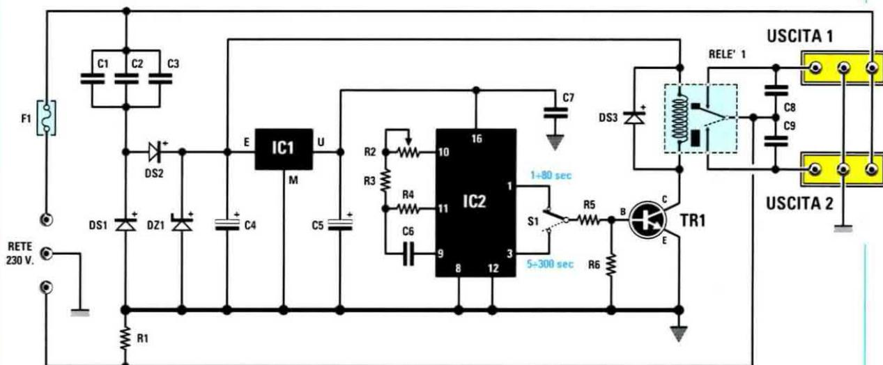
Fig.4 Come potete vedere dal disegno dello schema elettrico, per ridurre la tensione di rete non abbiamo utilizzato il solito trasformatore, ma i tre condensatori C1-C2-C3, che, attraversati da una corrente alternata, si comportano come una resistenza, il cui valore dipende dalla frequenza. Nell'articolo è spiegato come dimensionare questi condensatori.
