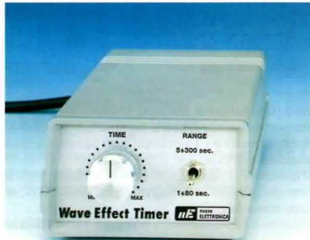
Fig.3 Per programmare l'effetto onda adatto al vostro acquario utilizzate il potenziometro e il deviatore.
