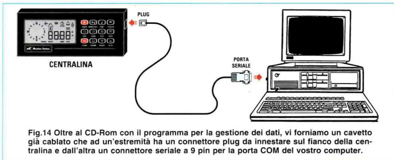
tipo plug **RJ45** da innestare nella centralina, mentre all'altra estremità ha un **connettore seriale a 9 pin** per il collegamento con la porta di comunicazione COM del vostro computer.
