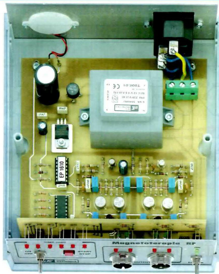
Fig.8 Sul piano del mobile plastico viene fissato il circuito stampato LX.1610 utilizzando 4 viti autofilettanti. Sul pannello posteriore montate la Cicalina CP1 e la Presa a vaschetta dei 230 volt (vedi fig.9), mentre sul pannello frontale fissate i due bocchettoni Uscita A e Uscita B ai quali collegherete i Panni Irradianti.
