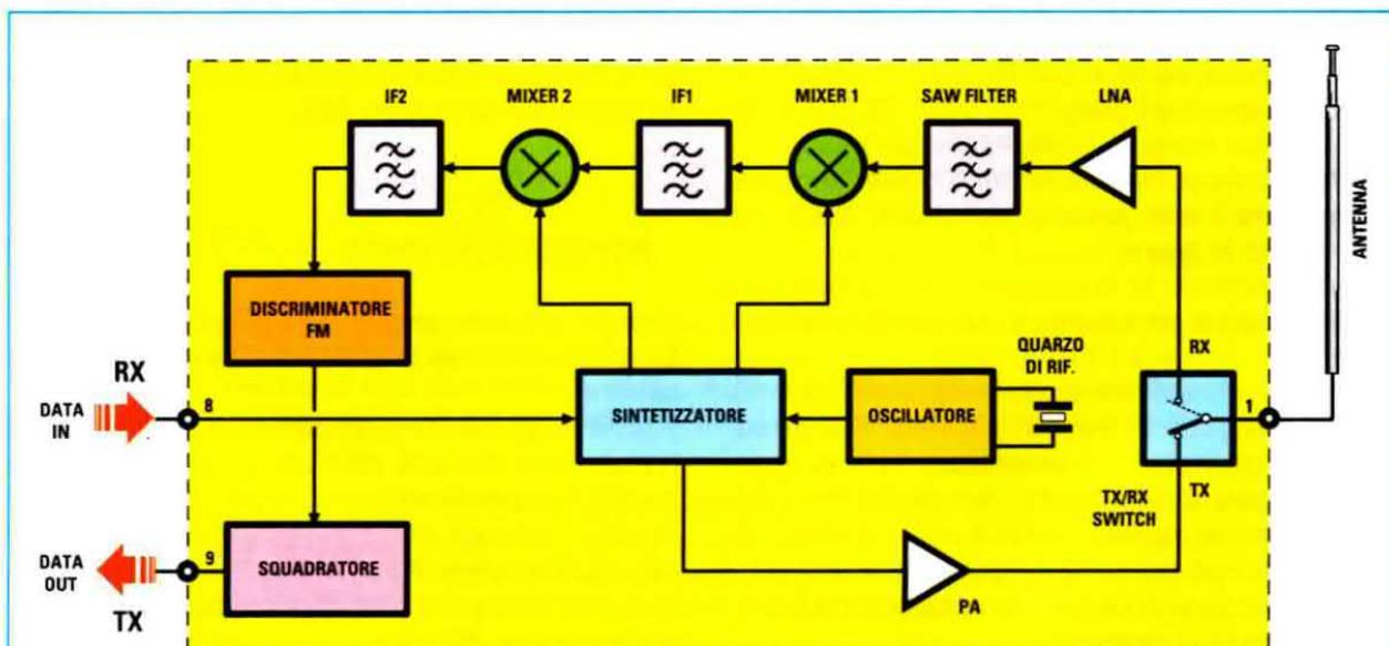
Fig.4 Nello schema a blocchi sono rappresentate le principali funzioni del transceiver KM01.50. Il segnale da trasmettere **RX** viene inviato al circuito Sintetizzatore e da questo tramite lo switch **RX-TX** all'antenna. Il segnale ricevuto dall'antenna, dopo avere attraversato una serie di filtri, viene inviato al Discriminatore FM che lo separa dalla portante e al circuito Squadratore che ricostruisce il segnale **TX** in forma digitale.
