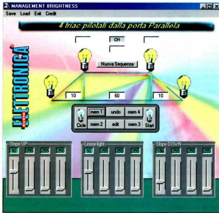
Fig.26 Per impostare le sequenze di accensione e spegnimento, cliccate su Management Brightness di fig.25. Per la descrizione dettagliata di una programmazione vi rimandiamo alla lettura dell'articolo.
