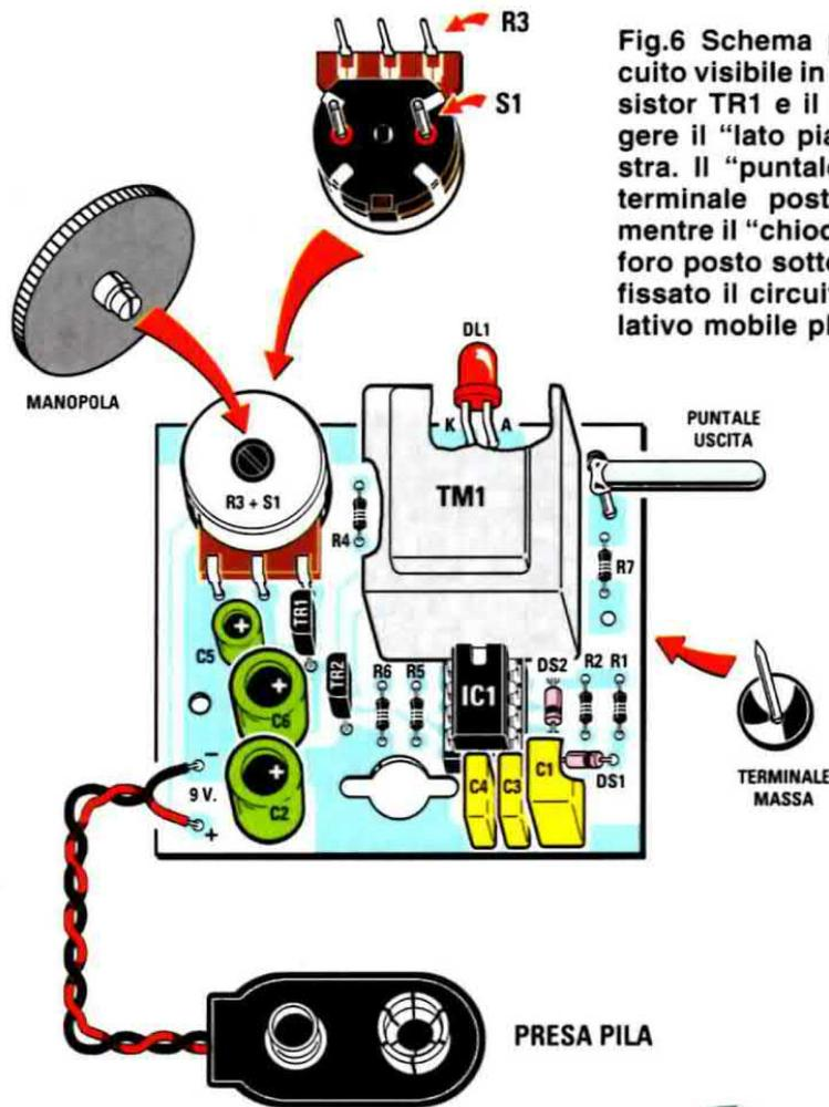
Fig.6 Schema pratico di montaggio del circuito visibile in fig.3. Quando inserirete il transistor TR1 e il darlington TR2, dovrete rivolgere il "lato piatto" del loro corpo verso destra. Il "puntale" d'uscita andrà saldato sul terminale posto sopra alla resistenza R7, mentre il "chiodo" di massa andrà inserito nel foro posto sotto la resistenza R7, dopo avere fissato il circuito stampato all'interno del relativo mobile plastico.
