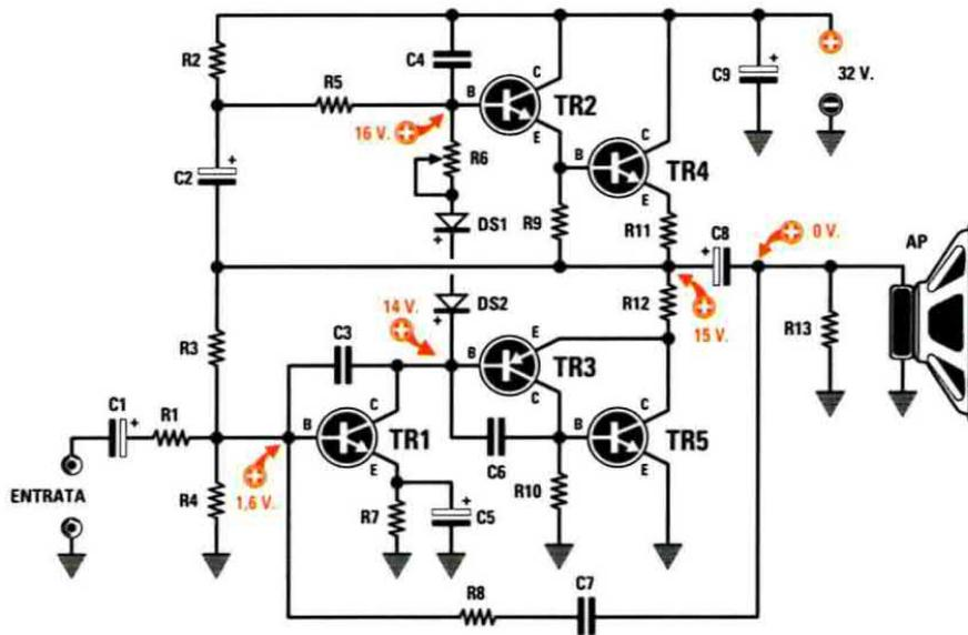
Fig.2 Schema elettrico dell'amplificatore Hi-Fi tutto a transistor in grado di erogare una potenza di 10-12 Watt su un carico di 8 ohm. Il trimmer R6 va tarato per far assorbire all'amplificatore una corrente di circa 70 mA senza applicare sull'ingresso nessun segnale. In fig.4 è riportato lo schema pratico.
