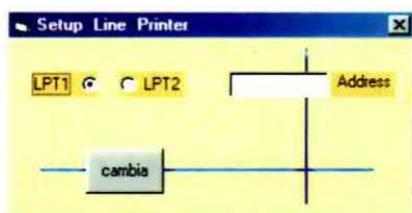
Fig.24 Utilizzate la finestra Setup Line Printer per configurare la porta parallela alla quale avete collegato la scheda LX.1613. Se la porta utilizzata corrisponde ad un indirizzo diverso da LPT1 o LPT2, inserite in Address l'indirizzo in decimale.
