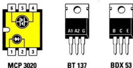
Fig.6 Connessioni dei componenti utilizzati nella scheda triac LX.1584. Le connessioni del fotodiaco MCP.3020 sono viste da sopra, mentre quelle del triac BT.137 e del transistor darlington BDX.53 sono viste frontalmente dal lato plastico.
