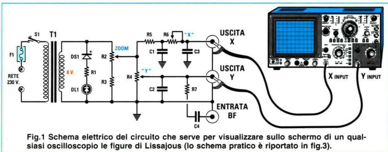
Fig.1 Schema elettrico del circuito che serve per visualizzare sullo schermo di un qualsiasi oscilloscopio le figure di Lissajous (lo schema pratico è riportato in fig.3).
