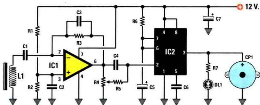
Fig.2 Schema elettrico del rivelatore di materiale magnetico. Avvicinando un oggetto magnetico al nucleo ferrocubo inserito all'interno della bobina L1, il diodo led DL1 si accenderà e la cicalina emetterà una nota acustica.
