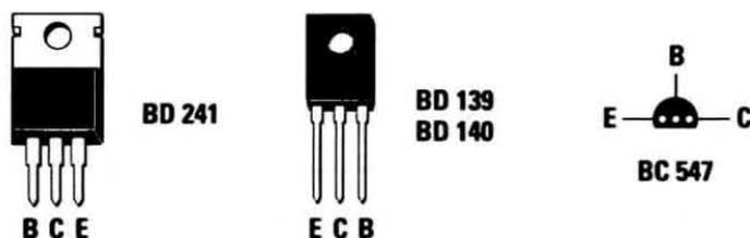
Fig.8 Connessioni viste frontalmente dei transistor finali tipo BD.241 e pilota BD.139 e BD.140. Le connessioni E-B-C del transistor preamplificatore BC.547 sono viste invece da sotto.
