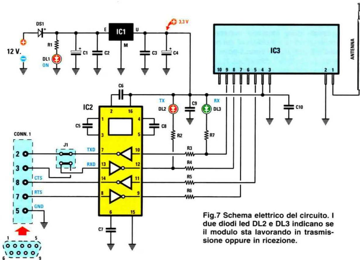
Fig.7 Schema elettrico del circuito. I due diodi led DL2 e DL3 indicano se il modulo sta lavorando in trasmissione oppure in ricezione.
