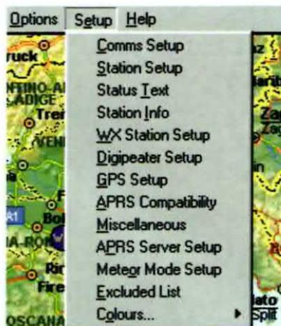
Fig.2 Per configurare la stazione APRS come stazione meteo, cliccate sulla voce **Setup** del programma UI-VIEW e scegliete prima **Station Setup** (vedi fig.3) e poi **WX Station setup** (vedi fig.4).
