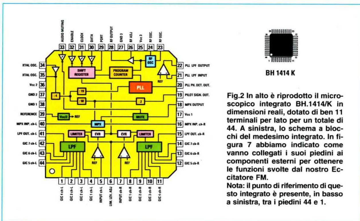
Fig.2 In alto è riprodotto il microscopico integrato BH.1414/K in dimensioni reali, dotato di ben 11 terminali per lato per un totale di 44. A sinistra, lo schema a blocchi del medesimo integrato. In figura 7 abbiamo indicato come vanno collegati i suoi piedini ai componenti esterni per ottenere le funzioni svolte dal nostro Eccitatore FM.
