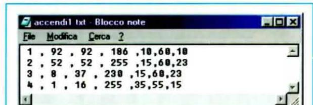
**Fig.30** Cliccando sul tasto Edit in fig.26 aprite qualsiasi sequenza già salvata come file .txt. Il primo numero di ogni riga indica la lampada, seguono i tre valori di Slope Up, Linear-light e Slope Down (vedi fig.26) e per finire i secondi impostati.
