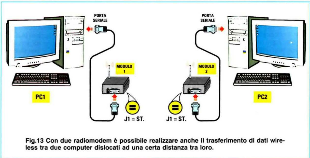
Fig.13 Con due radiomodem è possibile realizzare anche il trasferimento di dati wireless tra due computer dislocati ad una certa distanza tra loro.
