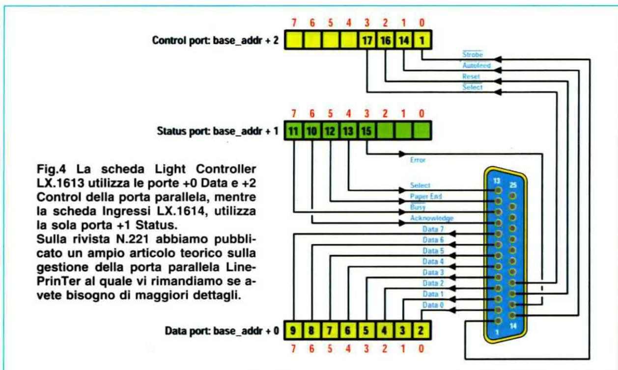
**Fig.4** La scheda Light Controller LX.1613 utilizza le porte +0 Data e +2 Control della porta parallela, mentre la scheda Ingressi LX.1614, utilizza la sola porta +1 Status. Sulla rivista N.221 abbiamo pubblicato un ampio articolo teorico sulla gestione della porta parallela Line-Printer al quale vi rimandiamo se avete bisogno di maggiori dettagli.
