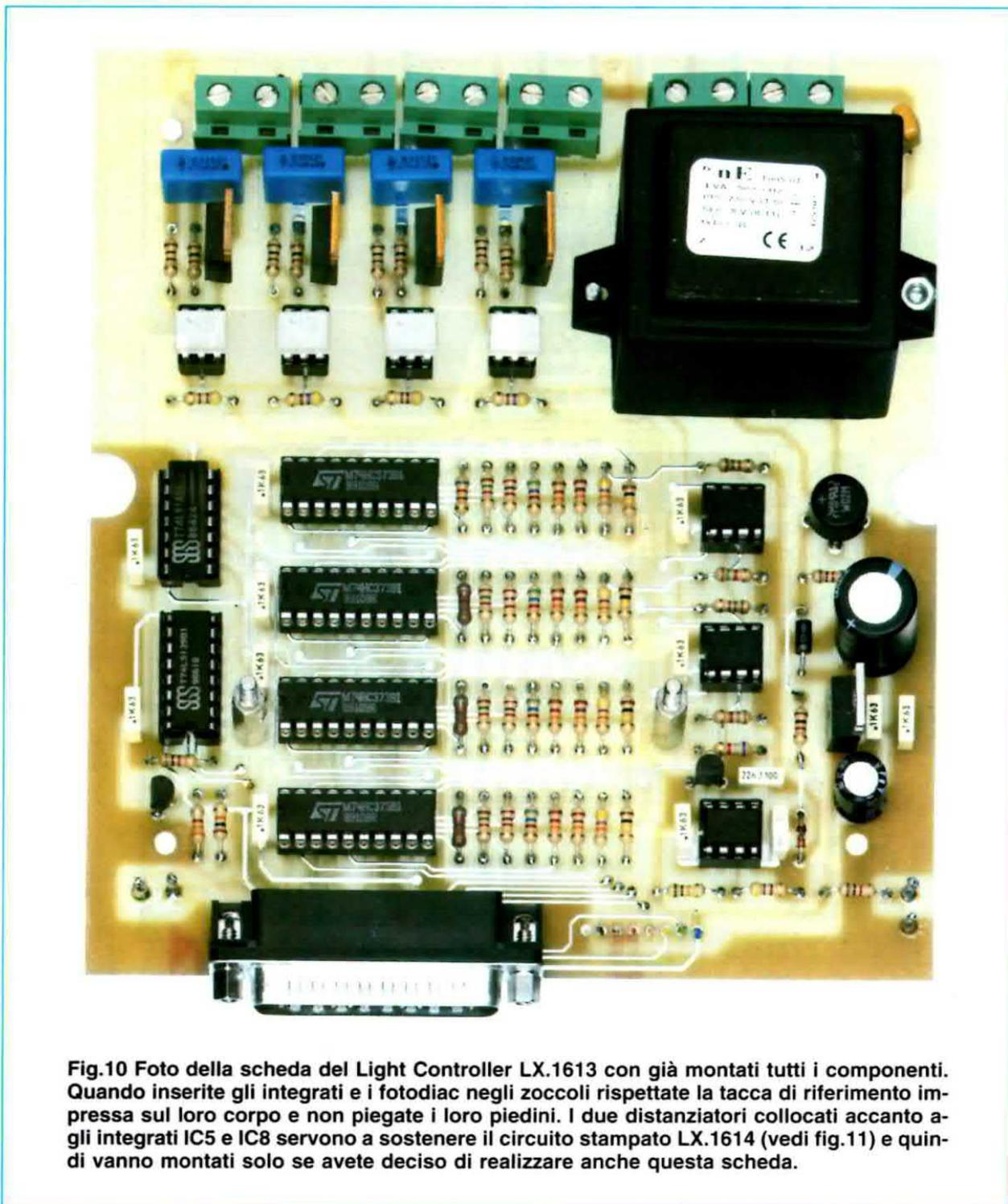
**Fig.10** Foto della scheda del Light Controller LX.1613 con già montati tutti i componenti. Quando inserite gli integrati e i fotodiac negli zoccoli rispettate la tacca di riferimento impressa sul loro corpo e non piegate i loro piedini. I due distanziatori collocati accanto agli integrati IC5 e IC8 servono a sostenere il circuito stampato LX.1614 (vedi fig.11) e quindi vanno montati solo se avete deciso di realizzare anche questa scheda.
