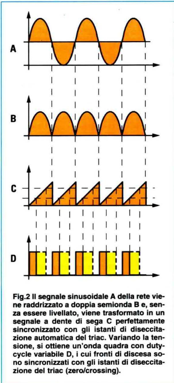
**Fig.2** Il segnale sinusoidale **A** della rete viene raddrizzato a doppia semionda **B** e, senza essere livellato, viene trasformato in un segnale a dente di sega **C** perfettamente sincronizzato con gli istanti di diseccitazione automatica del triac. Variando la tensione, si ottiene un'onda quadra con duty-cycle variabile **D**, i cui fronti di discesa sono sincronizzati con gli istanti di diseccitazione del triac (zero/crossing).
