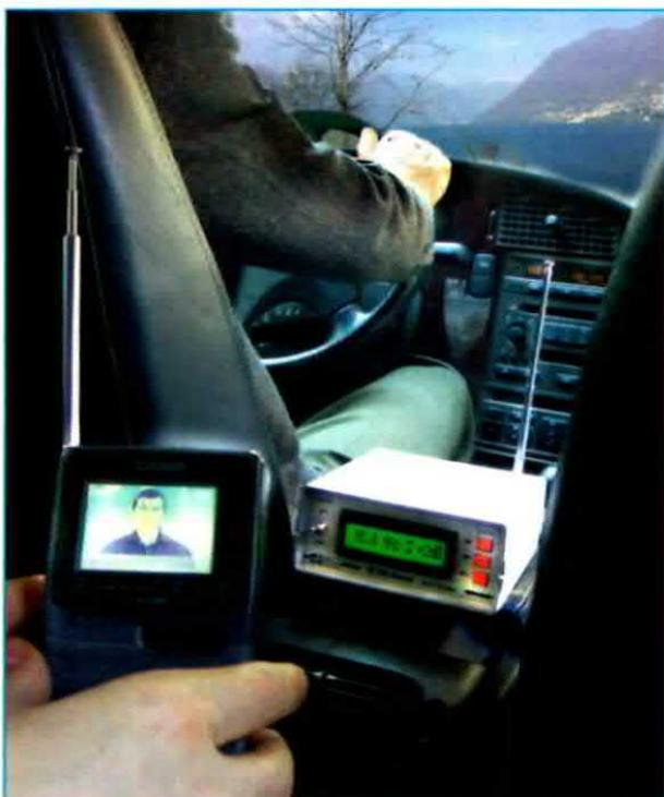
**Fig.5** Se collegate la presa audio di un piccolo televisore portatile all'Eccitatore FM, potrete utilizzare l'impianto stereo della vostra auto o del vostro camper per potenziare la riproduzione sonora.
