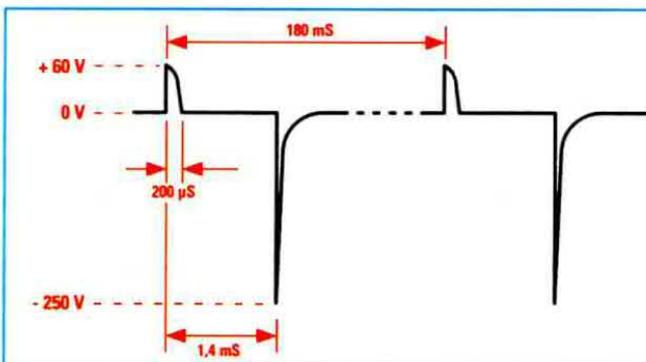
**Fig.2** Dal secondario del trasformatore **TM1** (vedi fig.3) escono degli strettissimi impulsi "negativi" della durata di 1,47 millisecondi (tempo **T/on**) seguiti da una pausa di 180 millisecondi (tempo **T/off**).
