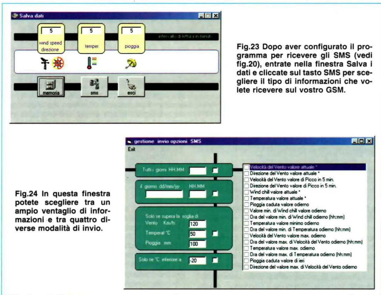
Fig.23 Dopo aver configurato il programma per ricevere gli SMS (vedi fig.20), entrate nella finestra Salva i dati e cliccate sul tasto SMS per scegliere il tipo di informazioni che volete ricevere sul vostro GSM.
