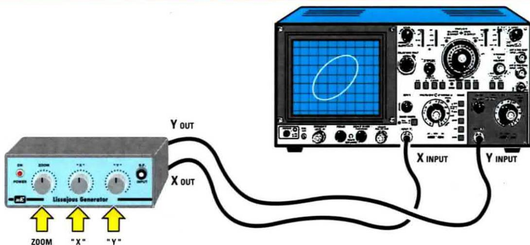
**Fig.7** Per collegare i due BNC d'uscita FEMMINA posti sul retro del mobile, potete utilizzare due spezzoni di cavo coassiale lunghi circa 50 cm., provvisti alle due estremità di due BNC MASCHIO. Se in commercio non trovate questo filo, ricordate che noi ve lo possiamo fornire già cablato.
