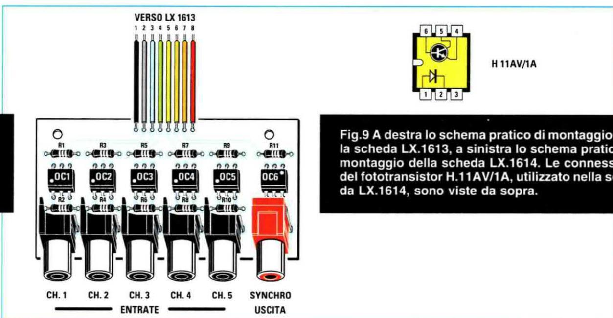
Fig.9 A destra lo schema pratico di montaggio della scheda LX.1613, a sinistra lo schema pratico di montaggio della scheda LX.1614. Le connessioni del fototransistor H.11AV/1A, utilizzato nella scheda LX.1614, sono viste da sopra.
