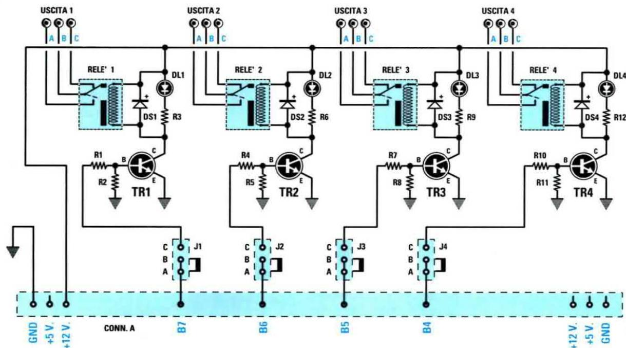
Fig.2 Schema elettrico della scheda con 4 relè siglata LX.1583. Due sono le logiche di gestione delle uscite dei relè: usando i contatti A-B (normalmente aperto), quando il relè è attivo il carico si collega (logica positiva), usando i contatti B-C (normalmente chiuso), quando il relè si attiva il carico si scollega (logica negativa).
