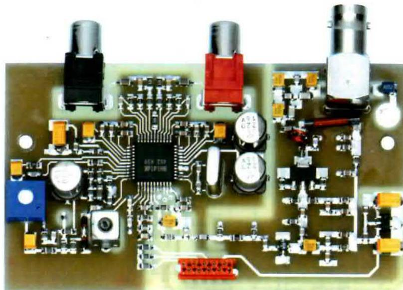
**Fig.10** Foto a grandezza naturale dello stadio KM.1619 che vi forniamo già montato e tarato. Se userete l'antenna a Dipolo di fig.33 non dovrete fissare sul circuito stampato l'antenna a stilo che troverete nel kit. In basso, al centro del circuito stampato, è visibile il connettore femmina che vi servirà per innestare la piattina già cablata che lo collegherà al circuito stampato del Display (vedi figg.6 e 12).
