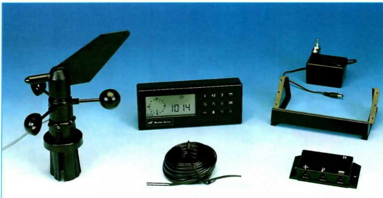
**Fig.32** La Weather Station KM.100 comprende i seguenti componenti: un anemometro con annesso anemoscopio, un sensore di temperatura, un alimentatore a 12 volt, la connection box per il collegamento dei dispositivi e la centralina completa di supporto.
