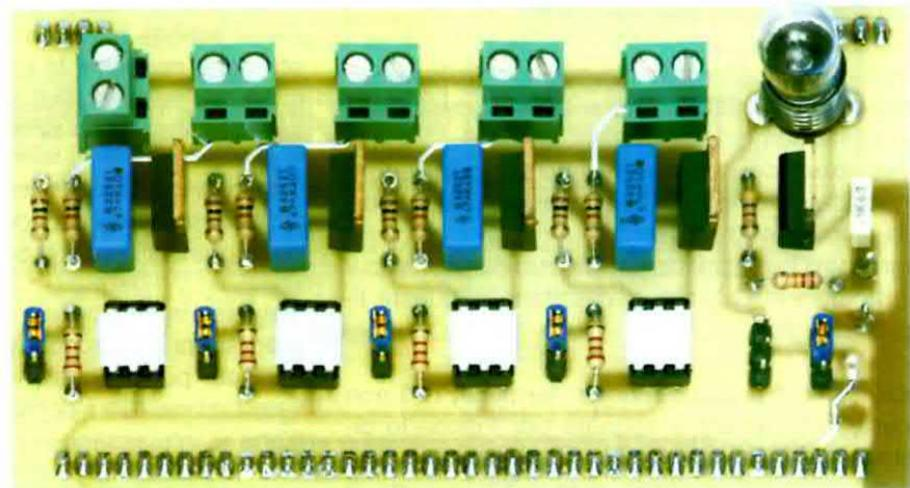
Fig.9 Foto del montaggio della scheda triac LX.1584.
