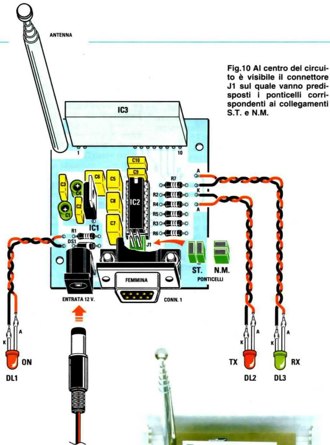
Fig.10 Al centro del circuito è visibile il connettore J1 sul quale vanno predisposti i ponticelli corrispondenti ai collegamenti S.T. e N.M.
