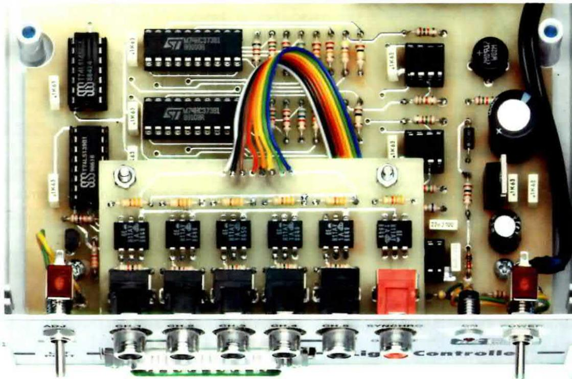
Fig.13 Foto della scheda Ingressi siglata LX.1614 montata sul circuito stampato LX.1613. Prima di bloccare questa scheda sulle due torrette metalliche distanziatrici, saldate nei rispettivi fori la piastrina a 8 fili proveniente dal circuito LX.1613.
