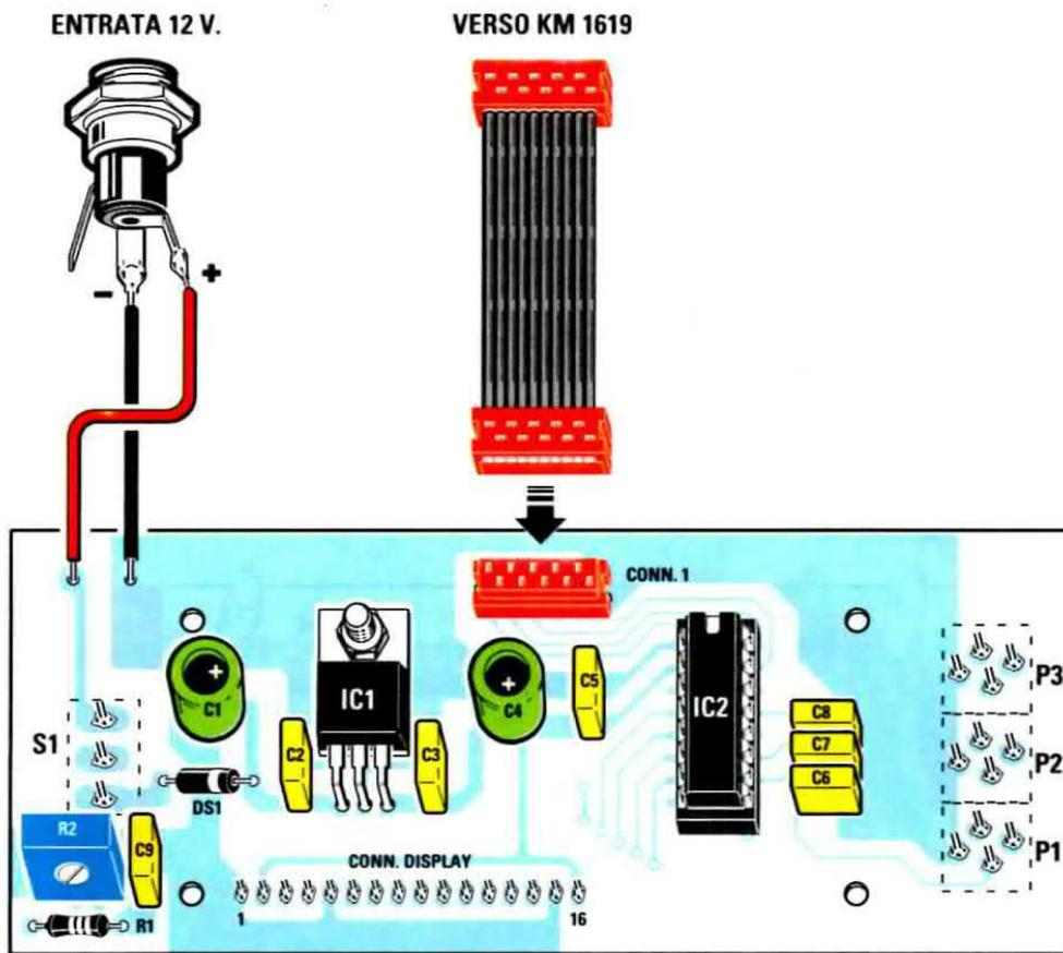
Fig.12 Il circuito stampato LX.1618 è un doppia faccia con fori metallizzati, quindi sul lato visibile in questa figura monterete i componenti qui indicati e sul lato opposto i componenti visibili in fig.14. Quando inserirete il micro IC2 dovrete rivolgere la tacca a U verso l'alto, mentre quando collegherete i due fili +/- al connettore per entrare con i 12 volt, dovrete collegare il filo "positivo" al terminale centrale.
