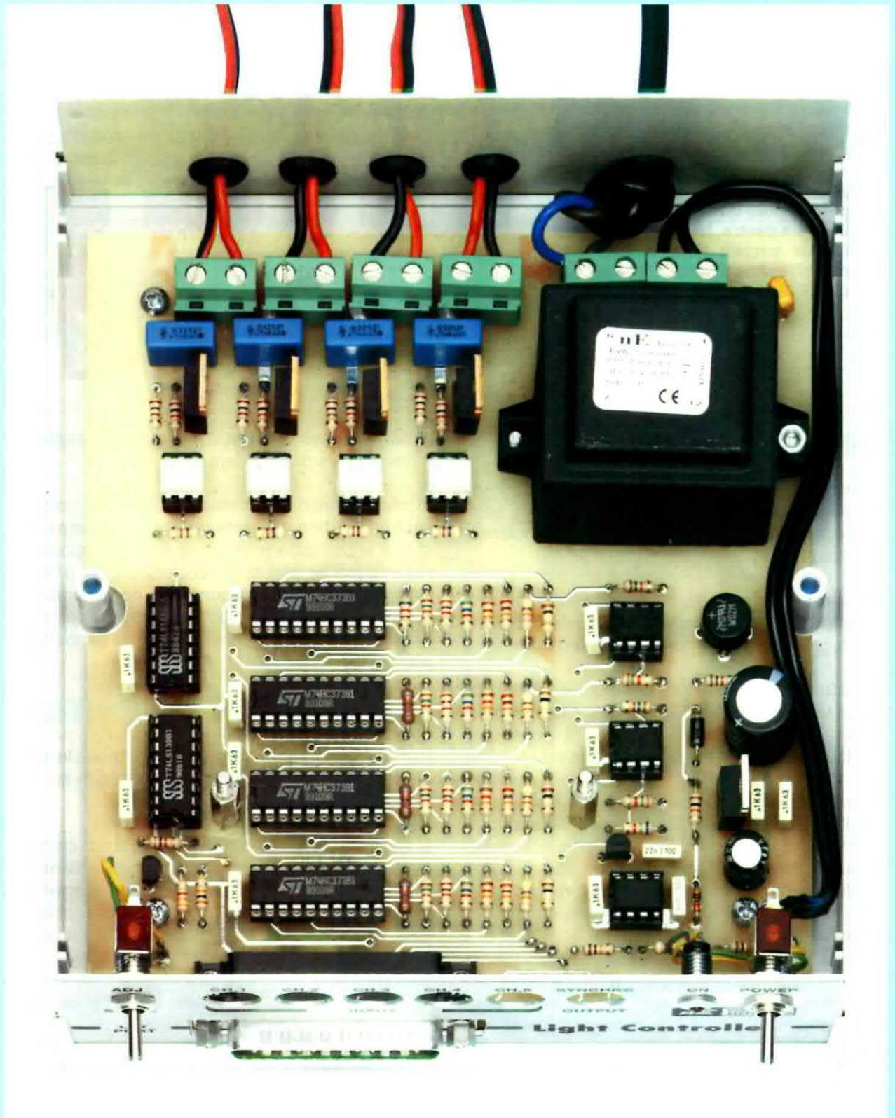
Fig.12 Foto della scheda LX.1613 collocata nel mobile plastico. Prima di inserire il circuito, dovete montare sulla mascherina anteriore l'interruttore di accensione, il deviatore e la ghiera cromata per il diodo led, quindi dovete infilare la mascherina nelle apposite guide e solo dopo potete collocare la scheda nel mobile avendo l'accortezza di far uscire il connettore maschio da 25 poli dal foro già predisposto.
