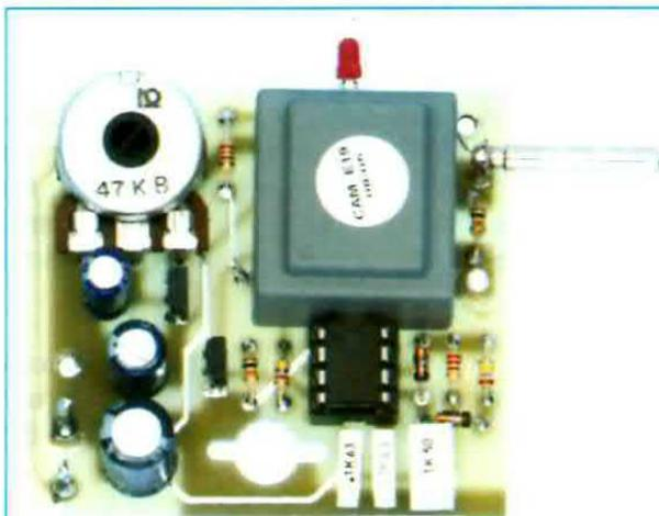
Fig.5 Foto del circuito a montaggio ultimato. Sulla destra del trasformatore TM1 esce il piccolo "puntale" che dovrete appoggiare sulle zone da elettrostimolare illustrate nelle figg.8-9.
