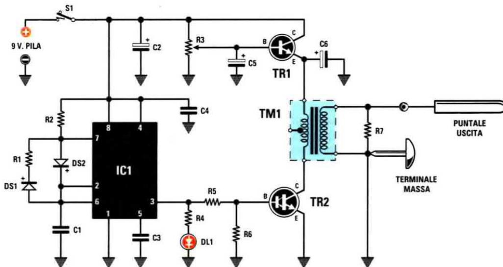
Fig.3 Schema elettrico dell'elettrostimolatore che vi servirà per smettere finalmente di fumare. Come noterete, per la sua realizzazione occorrono pochi componenti.
