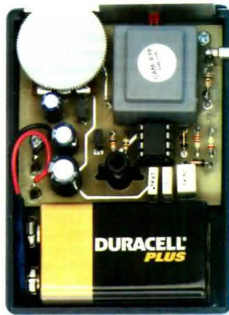
la da **9 volt** ruotando la manopola a disco in modo da far scattare l'interruttore **S1**, vedrete subito **lampeggiare** il diodo led a conferma che non avete commesso alcun errore nel vostro montaggio.
