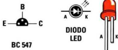
Fig.3 Connessioni del transistor NPN BC.547 viste da sotto con la parte piatta del corpo rivolta verso il basso. Quando collegate i diodi led, ricordate che il terminale più lungo è l'Anodo.
