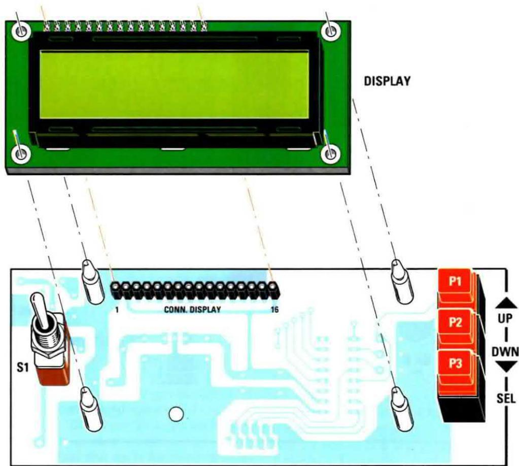
Fig.14 In questo lato del circuito stampato LX.1618 dovrete inserire il Connettore femmina a 16 fori necessario per innestare il connettore maschio visibile nelle figg.16-17-18. Sulla sinistra dovrete fissare l'interruttore a levetta siglato S1 e sulla destra i tre pulsanti indicati P1-P2-P3. Nei 4 fori presenti sul circuito stampato innesterete i distanziatori plastici necessari per bloccare il corpo del display.
