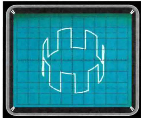
Fig.20 Se applicando sull'ingresso BF un'onda QUADRA sullo schermo appare questa figura composta da ben 7 onde complete, si può affermare che il Generatore BF modula il segnale con una frequenza di  $7 \times 50 = 350 \text{ Hz}$ .
