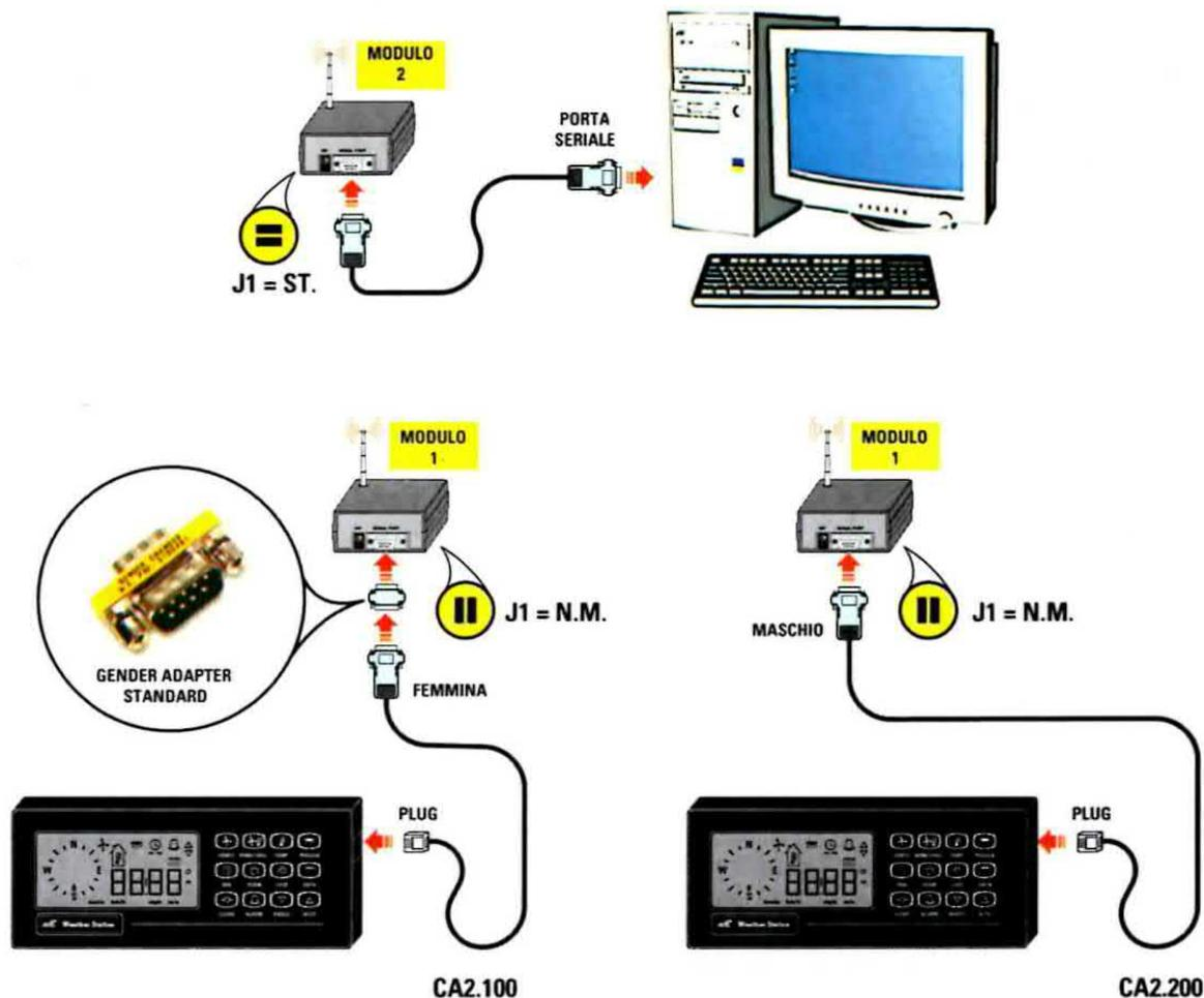
**Fig.12** In figura sono rappresentati due esempi di collegamento della stazione meteorologica al modulo trasmittente e il collegamento del modulo ricevente al PC oltre alle configurazioni dei ponticelli da adottare sui moduli. Sono inoltre visibili i due diversi tipi di cavo (codice CA2.100 e CA2.200) che possono essere utilizzati per collegare la centralina al modulo 1.
