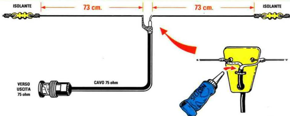
Fig.33 Se desiderate collegare a questo Eccitatore FM un Dipolo esterno per poter aumentare la sua portata, procedete come illustrato in figura.
