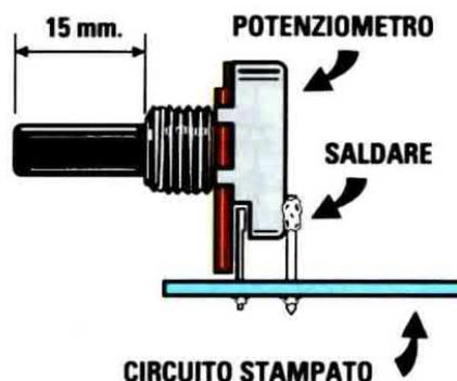
**Fig.2** Prima di fissare sul circuito stampato i 3 potenziometri (vedi fig.3), dovete accorciare alla medesima lunghezza i loro perni. Per evitare che il potenziometro capti del ronzio di alternata a 50 Hz, dovete collegare il suo corpo metallico alla "massa" del circuito stampato, utilizzando un corto spezzone di filo di rame nudo.
