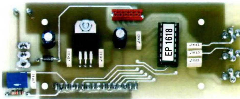
Fig.13 Ecco come si presenta il circuito LX.1618 una volta ultimato il montaggio dei vari componenti. Prima di fissare l'integrato stabilizzatore IC1 dovrete ripiegare a L i suoi tre terminali. Il trimmer R2 visibile a sinistra serve per tarare il contrasto del Display LCD. Se il cursore di questo trimmer non viene tarato in modo corretto, sullo schermo del Display non vedrete apparire alcun numero.
