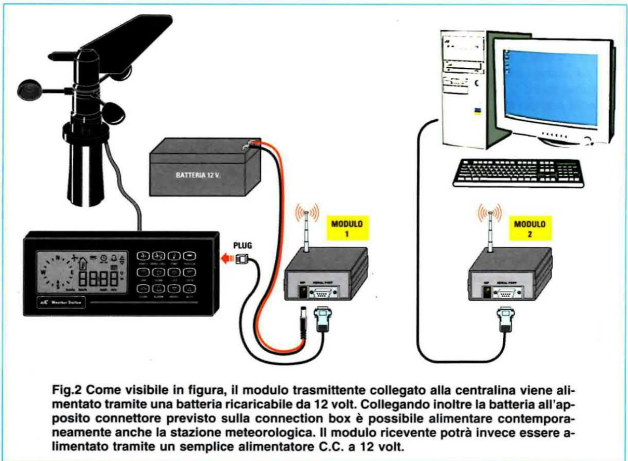
**Fig.2** Come visibile in figura, il modulo trasmettente collegato alla centralina viene alimentato tramite una batteria ricaricabile da 12 volt. Collegando inoltre la batteria all'apposito connettore previsto sulla connection box è possibile alimentare contemporaneamente anche la stazione meteorologica. Il modulo ricevente potrà invece essere alimentato tramite un semplice alimentatore C.C. a 12 volt.
