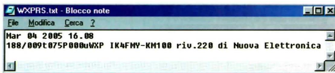
Fig.21 Il file WXPRS.TXT, generato dal nostro programma, racchiude le informazioni raccolte dalla centralina Weather Station. Questo file viene copiato anche nella directory del programma UI-VIEW, che lo utilizza per mandare i dati nella rete APRS. Nell'articolo vi spieghiamo come decodificarne e interpretarne le informazioni.
