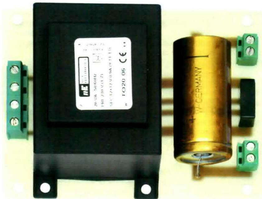
Fig.7 Foto dello stadio di alimentazione "non" stabilizzato come si presenta a montaggio ultimato. Questo alimentatore che eroga una tensione di circa 32 Volt e una corrente di 0,9 Amper può essere utilizzato per alimentare anche altri circuiti che richiedano questi valori di tensione e corrente.
