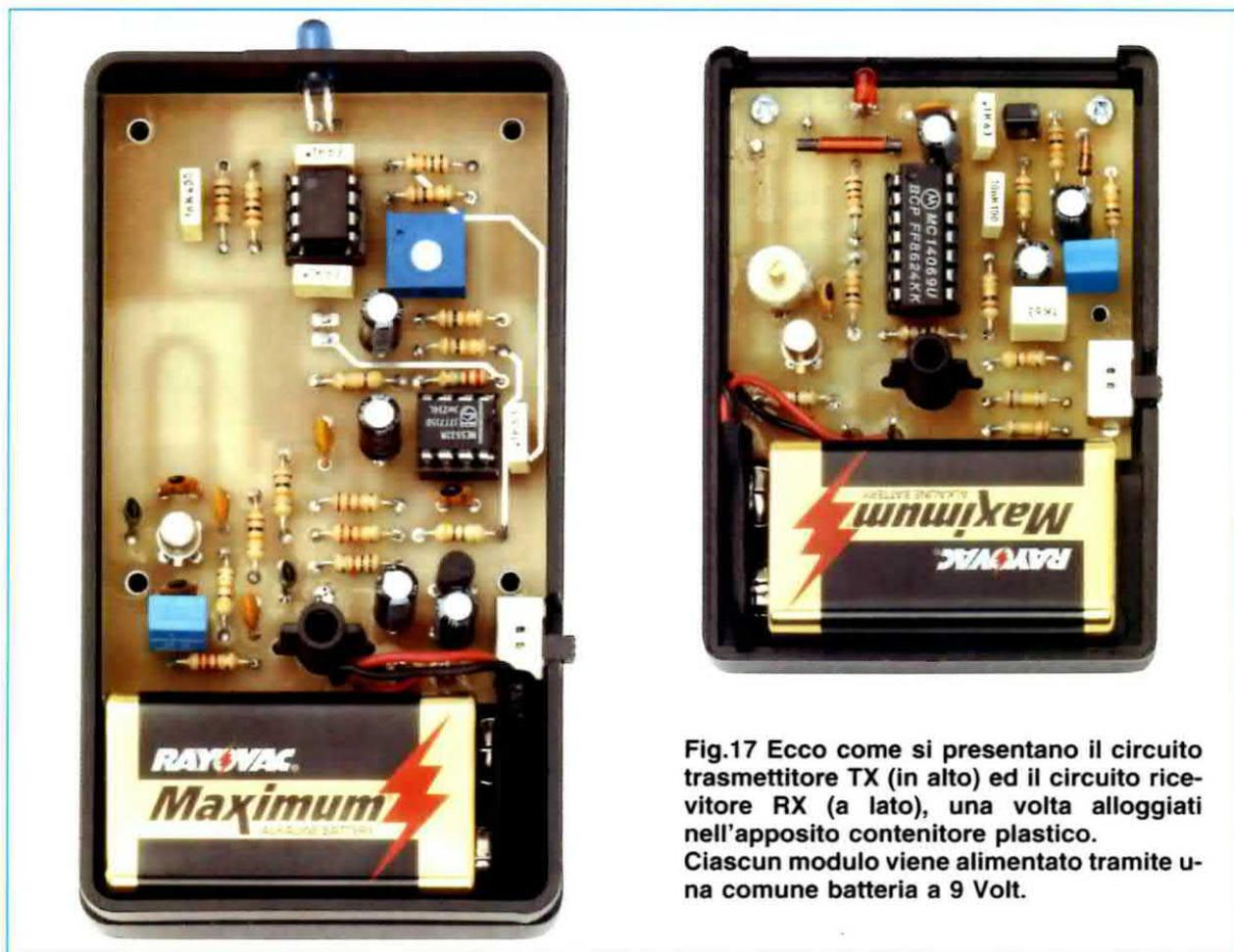
Fig.17 Ecco come si presentano il circuito trasmettitore TX (in alto) ed il circuito ricevitore RX (a lato), una volta alloggiati nell'apposito contenitore plastico. Ciascun modulo viene alimentato tramite una comune batteria a 9 Volt.
