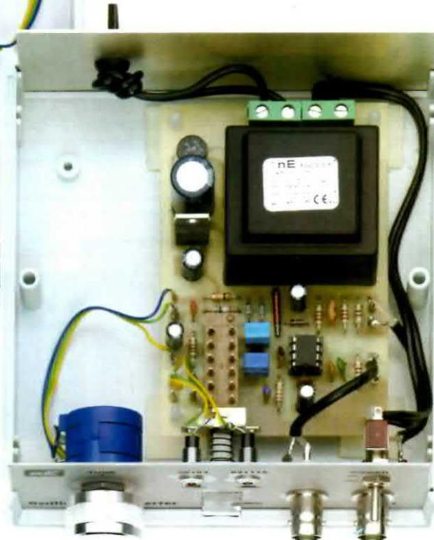
Fig.11 In questa foto l'interno del mobile è visto dal lato opposto. Per fissare la base del distanziatore plastico di sinistra sul piano del mobile, occorre tagliarlo.
