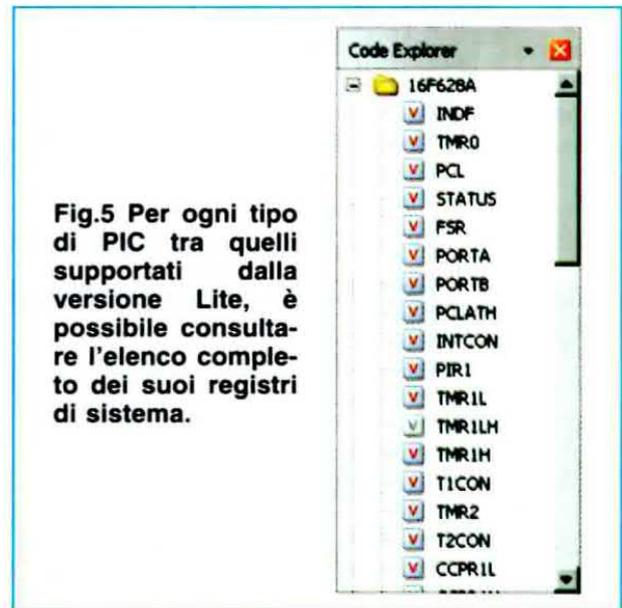
**Fig.5** Per ogni tipo di PIC tra quelli supportati dalla versione Lite, è possibile consultare l'elenco completo dei suoi registri di sistema.
