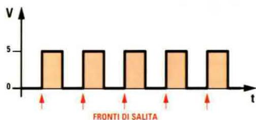
Fig.1 Sono i fronti di salita dell'onda quadra a scandire con precisione gli istanti di attivazione dei passi elementari necessari all'esecuzione di ogni singola istruzione.
