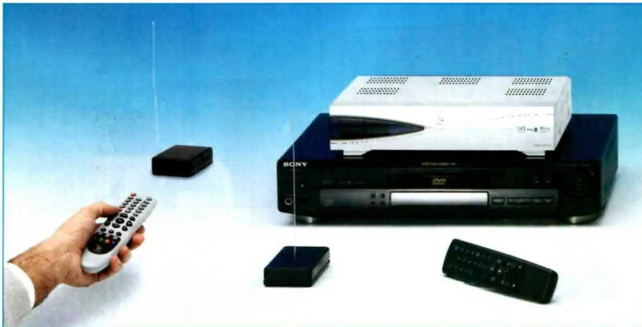
Fig.1 Il ripetitore per telecomando è composto da un modulo trasmettitore TX che riceve il segnale ad infrarosso dal telecomando e lo trasforma in un segnale a radiofrequenza, e da un modulo ricevitore RX che lo riconverte in un segnale ad infrarosso in grado di pilotare un decoder TV, un videoregistratore oppure un lettore DVD.
