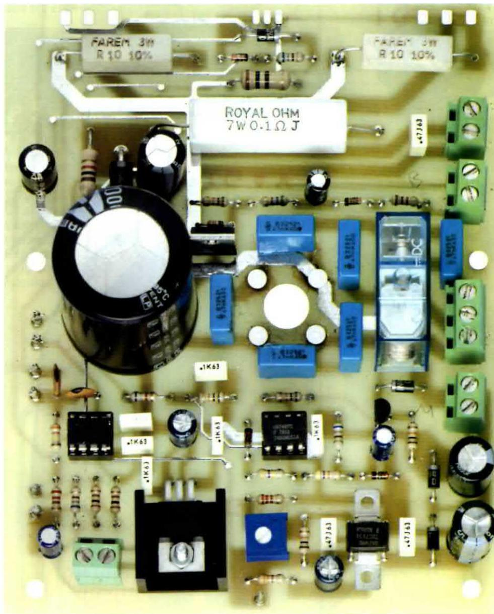
Fig.7 Foto del circuito stampato LX.1643. Note in basso a sinistra l'integrato stabilizzatore L7805 montato in posizione orizzontale sulla sua piccola aletta di raffreddamento. Il trimmer, sulla destra dell'integrato L7805, serve per tarare l'alimentatore in modo che al potenziometro dei VOLT ruotato tutto a sinistra corrisponda 0 volt in uscita.
