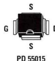
Fig.1 In questo disegno abbiamo raffigurato il corpo del mosfet siglato PD.55015. Rivolgendolo verso il basso la tacca di riferimento a forma di U impressa sul suo corpo, il terminale Gate si troverà sulla sinistra ed il terminale Drain sulla destra.
