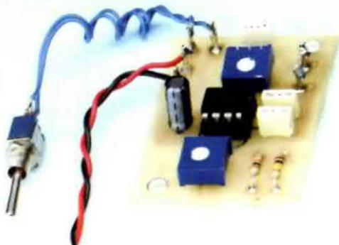
Questo strumento, chiamato **Signal-Tracer**, veniva utilizzato tempo addietro da tutti coloro che non disponevano della necessaria strumentazione per ricercare negli **amplificatori BF** o nelle **radio** gli stadi difettosi.
