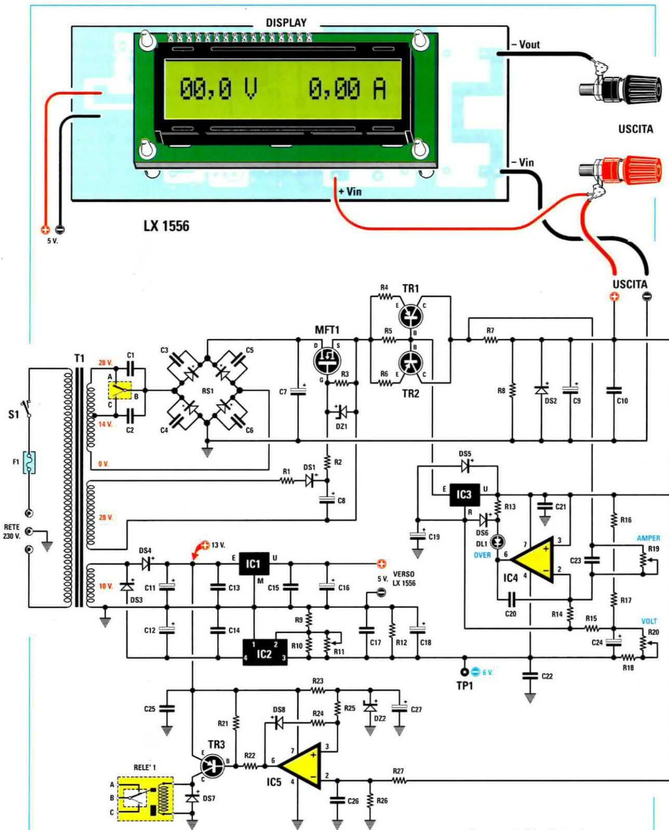
Fig.2 Schema elettrico dell'alimentatore LX.1643. I tre secondari del trasformatore toroidale, appositamente preparato per questo progetto, forniscono tutte le tensioni necessarie per alimentare il circuito e per prelevare in uscita una tensione da 0 a 25 volt.
