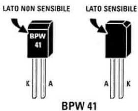
Fig.8 Schema pratico di montaggio del kit che abbiamo siglato LX.1641. Se in fase di montaggio eseguite delle perfette saldature e non sbaglierete a leggere il valore di una resistenza o di un condensatore, il circuito funzionerà immediatamente. Il lato sensibile del fotodiode ricevente BPW41 è quello sprovvisto di scritta, oppure quello con il lato destro smussato. Facciamo presente che il fotodiode BPW41 può essere sostituito anche da altri provvisti di sigla diversa o anche di forma diversa.
