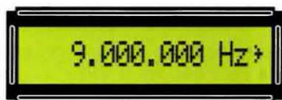
Fig.23 Impostato il Generatore in modo da ottenere sulla sua uscita una qualsiasi frequenza, potete variarla di pochi Hz-KHz-MHz utilizzando i tasti +/-.
