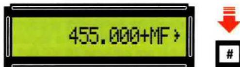
Fig.48 Digitate in Hz il valore della MF da sommare e premete il tasto # di conferma.
