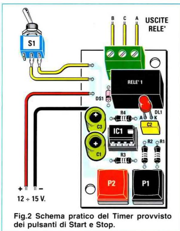
Fig.2 Schema pratico del Timer provvisto dei pulsanti di Start e Stop.
