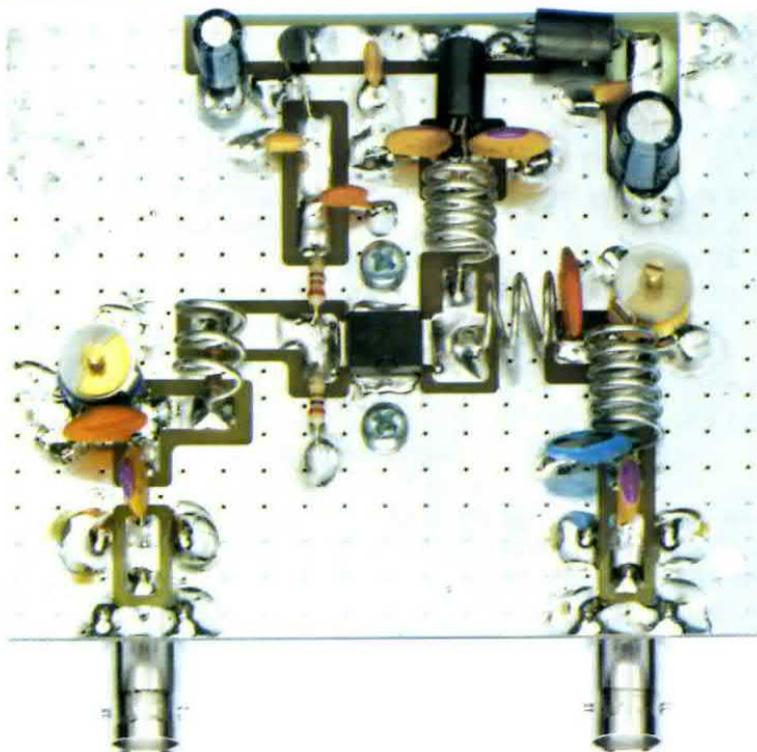
Fig.2 Foto del Lineare da 14-15 Watt come si presenta a montaggio ultimato. Tutti i terminali di ogni singolo componente vanno saldati direttamente sulle piste in rame del circuito stampato a doppia faccia come potete anche vedere nel disegno di fig.4.
