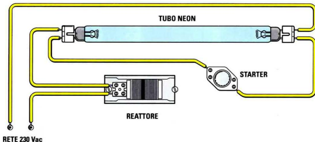
**Fig.12** Schema dei collegamenti di un tubo al neon. Gli elettrodi del tubo vengono alimentati dall'esterno con l'ausilio del reattore, collegato in serie al tubo, e dello starter, collegato in parallelo. Senza questi elementi, la lampada non si accende.
