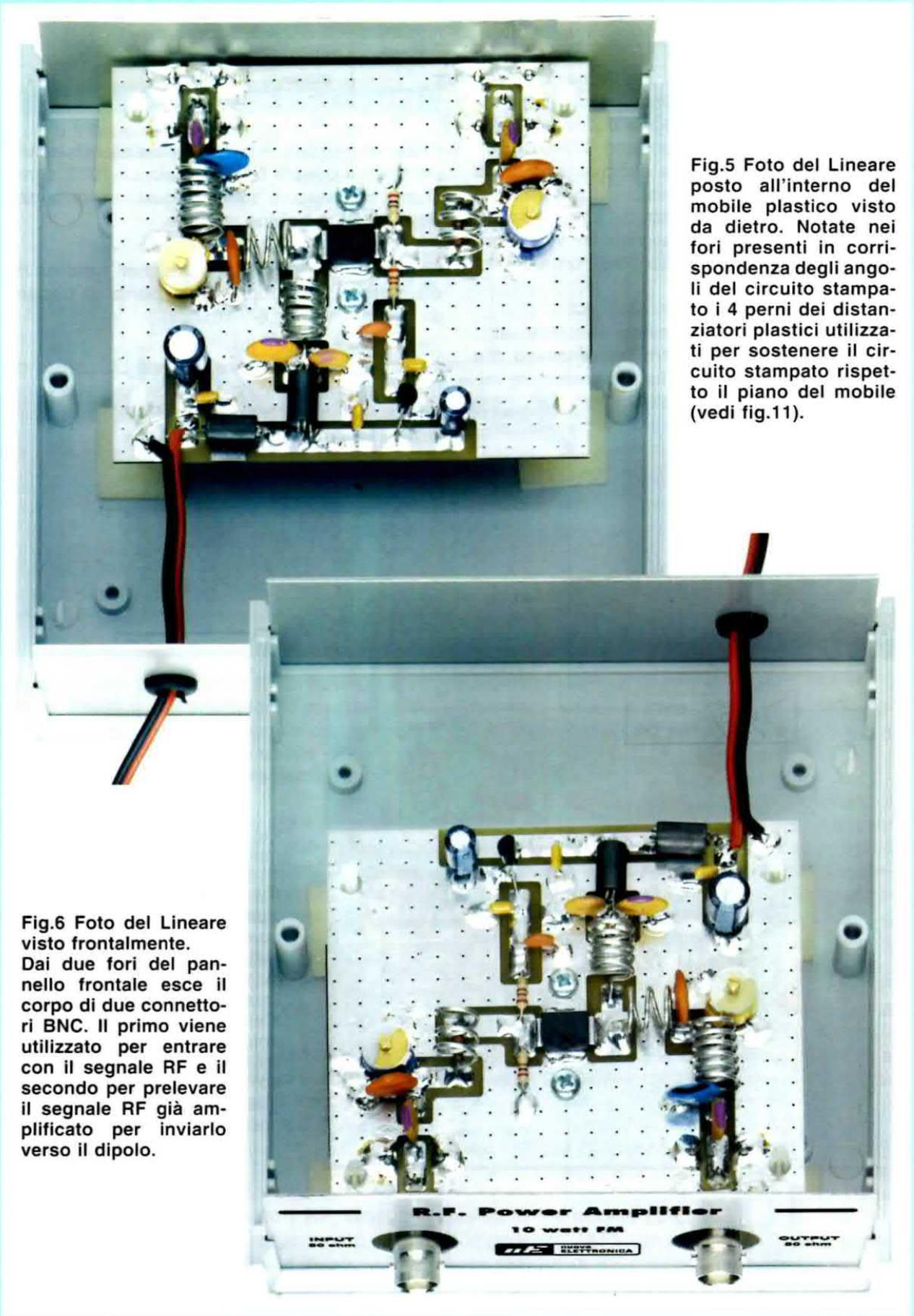
Fig.5 Foto del Lineare posto all'interno del mobile plastico visto da dietro. Notate nei fori presenti in corrispondenza degli angoli del circuito stampato i 4 perni dei distanziatori plastici utilizzati per sostenere il circuito stampato rispetto il piano del mobile (vedi fig.11).
