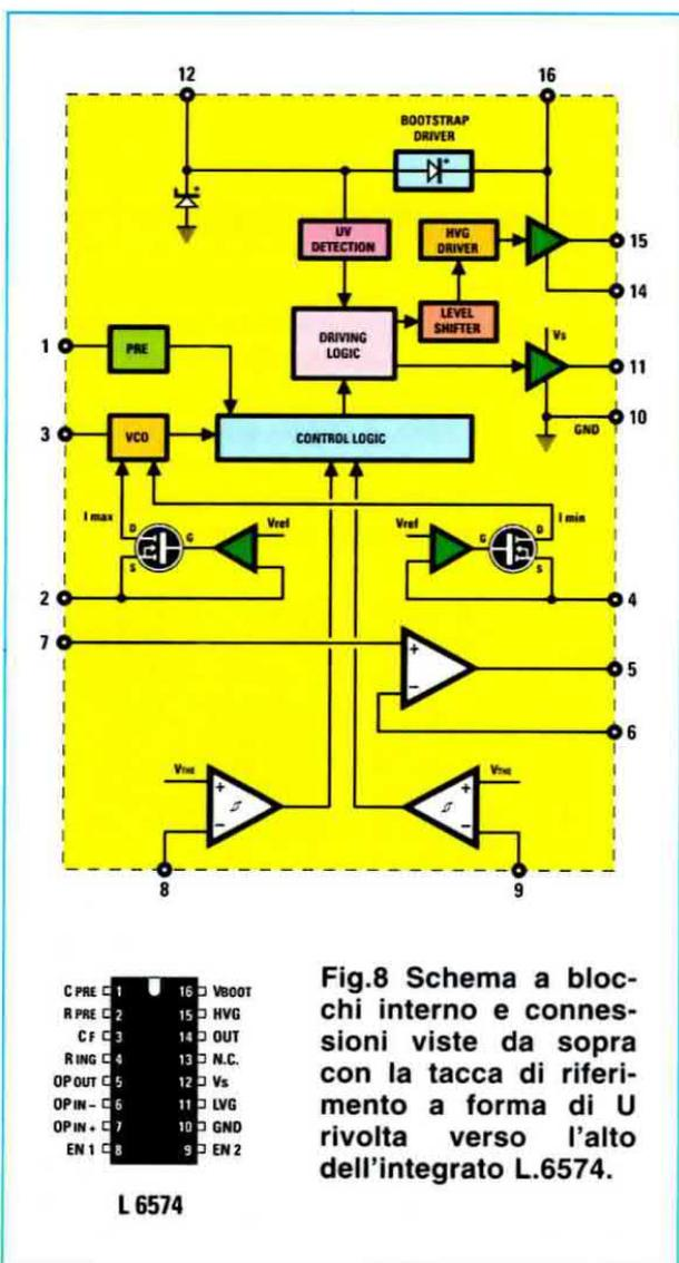
**Fig.8** Schema a blocchi interno e connessioni viste da sopra con la tacca di riferimento a forma di U rivolta verso l'alto dell'integrato **L.6574**.
