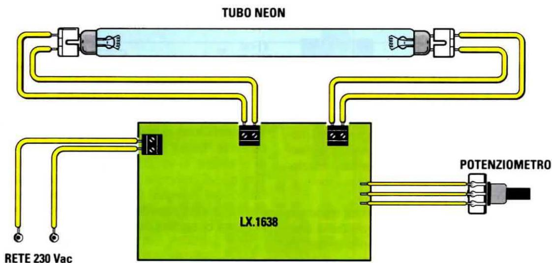
**Fig.13** Utilizzando il circuito per regolare l'intensità luminosa delle lampade fluorescenti, non avete più bisogno di reattore e starter, quindi, dopo averli scollegati, collegate gli elettrodi del tubo al neon tra le due morsettiere dello stampato LX.1638.
