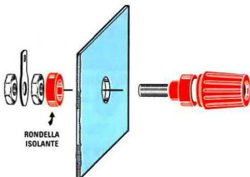
Fig.12 Disegno delle varie parti che compongono la boccia d'uscita. Per un corretto isolamento delle bocce dal pannello metallico frontale, rispettate la sequenza di assemblaggio qui raffigurata.
