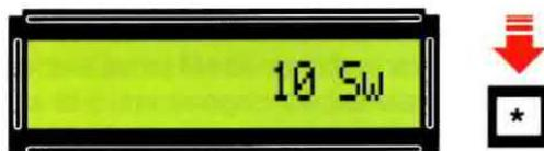
Fig.39 Premendo il tasto \* potrete scegliere la "velocità di scansione", che può essere di 1-10-100-1.000 Sw, ecc.
