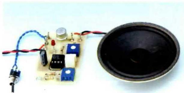
Con l'integrato **NE.555** più un transistor **NPN** di media potenza, ad esempio il **BC.300** oppure il **BD.139**, o altre sigle diverse, è possibile realizzare un semplice **metronomo** (vedi fig.1) con la possibilità di variare il **tempo** ruotando il trimmer **R2**.
