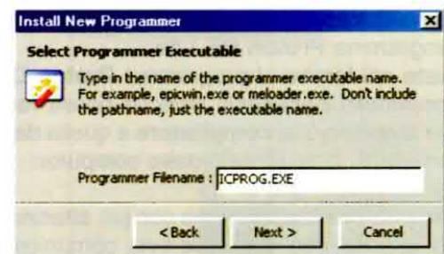
Fig.10 Ora definite l'eseguibile del programma digitando ICPROG.EXE e cliccando nuovamente sul tasto Next.
