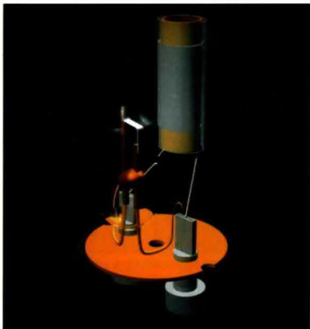
Fig.3 Alimentando la lampada, i contatti si chiudono e si genera un picco di tensione.
