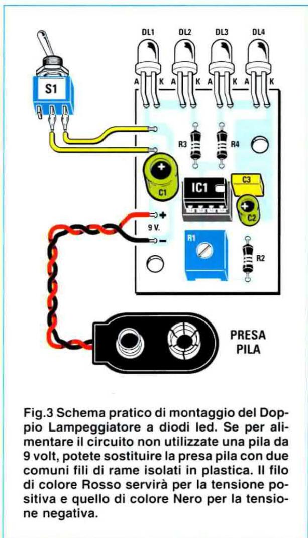
Fig.3 Schema pratico di montaggio del Doppio Lampeggiatore a diodi led. Se per alimentare il circuito non utilizzate una pila da 9 volt, potete sostituire la presa pila con due comuni fili di rame isolati in plastica. Il filo di colore Rosso servirà per la tensione positiva e quello di colore Nero per la tensione negativa.
