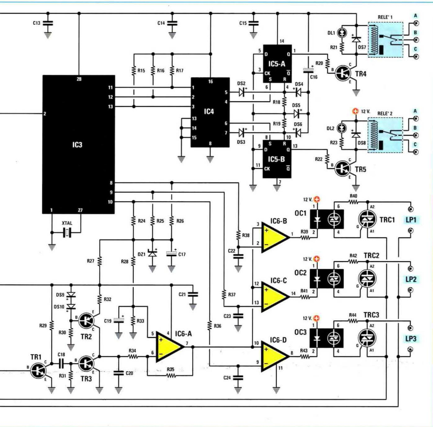
Fig.5 Per variare la luminosità delle lampade collegate alle uscite LP1-LP2-LP3 basta rilevare lo "zero crossing" dei 100 Hz tramite TR1, poi eccitare i Triac con un appropriato ritardo.
