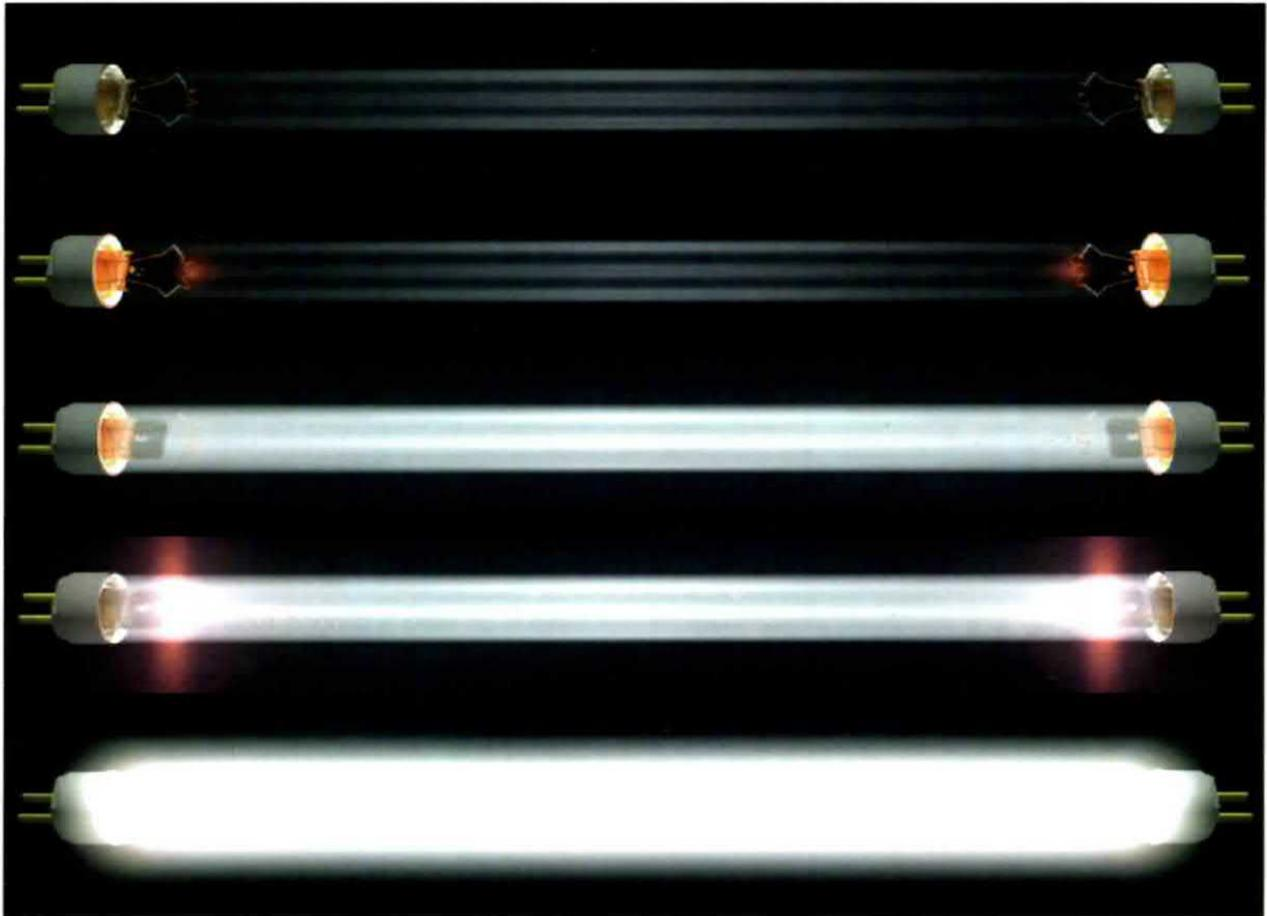
**Fig.5 Sequenza di accensione di una lampada a fluorescenza. La luce è prodotta da una scarica elettrica che passa nel tubo in vetro ripieno di gas. Questi tubi possono essere variamente ripiegati per soddisfare tutte le esigenze dei designers (vedi fig.7).**
