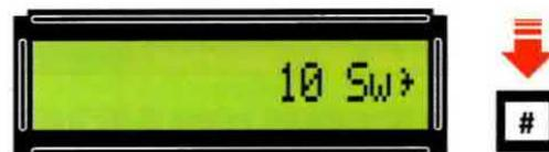
Fig.40 Scelto ad esempio "10 Sw", per avviare questa velocità premete il tasto di conferma # in modo che appaia il segno >.
