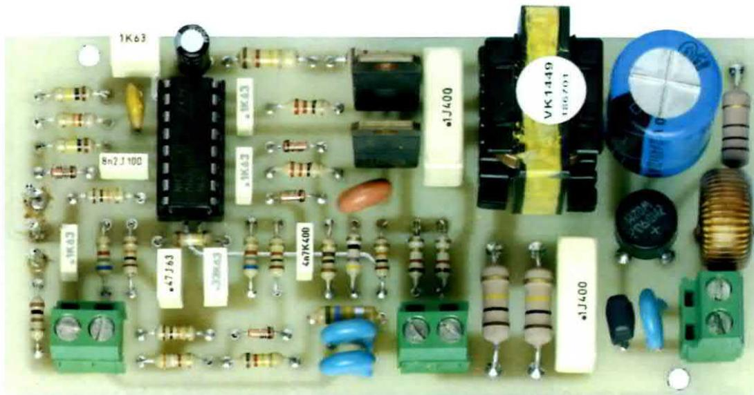
Fig.11 In questa foto potete vedere uno dei nostri primi circuiti-prototipo realizzati per le consuete prove di laboratorio. Osservate in particolare i mosfet di potenza ST.P9NK50Z, che hanno un lato del loro corpo metallico. Nel kit che abbiamo preparato troverete gli stessi mosfet, ma con il corpo esterno tutto di plastica (vedi fig.10).
