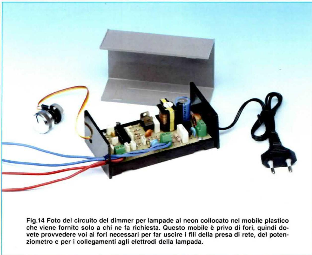
**Fig.14** Foto del circuito del dimmer per lampade al neon collocato nel mobile plastico che viene fornito solo a chi ne fa richiesta. Questo mobile è privo di fori, quindi dovete provvedere voi ai fori necessari per far uscire i fili della presa di rete, del potenziometro e per i collegamenti agli elettrodi della lampada.
