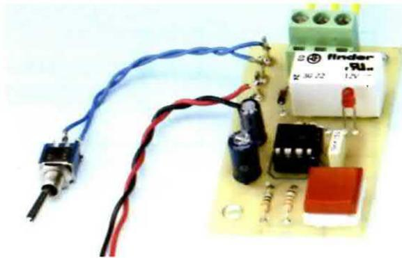
Questo circuito permette di **eccitare un relè** per un **tempo fisso** che noi stessi possiamo determinare utilizzando la formula:
