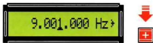
Fig.28 Premendo il tasto + la frequenza salirà di 1.000 Hz per volta. Arrivati alla frequenza di 9.009.000 Hz, questa continuerà a salire sempre di 1.000 Hz.
