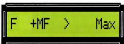
Fig.52 Se vi appare questa scritta significa che avete superato il valore di 120 MHz.
