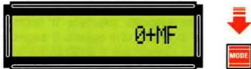
Fig.47 Premete "1 sola" volta il tasto Mode e sul display apparirà 0+MF.
