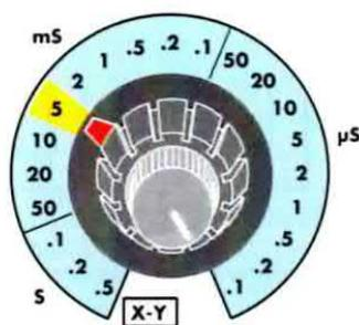
Fig.17 Se ruotiamo la manopola del Time/div. sui 5 mS e poi misuriamo una tensione alternata raddrizzata da un solo diodo, sullo schermo appariranno le sole semionde positive distanziate tra loro di 4 quadretti, perchè la frequenza pulsante è di 50 Hz. Sull'uscita applicate una resistenza R1 di carico del valore di 1.000 ohm.
