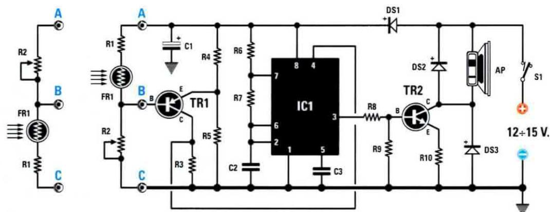
**Fig.1** Schema elettrico dell'Allarme sensibile alla luce che utilizza l'integrato NE.555. Il circuito emette una nota acustica quando la fotoresistenza FR1 viene oscurata. Se vogliamo ottenere una condizione opposta, basta invertire i collegamenti della fotoresistenza e del potenziometro, come visibile sulla sinistra dello schema elettrico.
