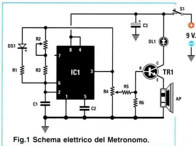
Fig.1 Schema elettrico del Metronomo.
