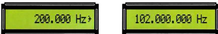
Fig.21 Se dopo aver ottenuto 200.000 Hz volete prelevare dall'uscita del Generatore DDS una frequenza di 102.000.000 Hz (102 MHz), scrivete questo numero e quindi premete il tasto # (cancellito) in modo che a destra appaia il segno di conferma >.
