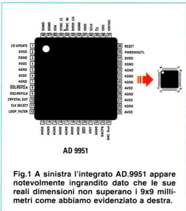
**Fig.1** A sinistra l'integrato **AD.9951** appare notevolmente ingrandito dato che le sue reali dimensioni non superano i 9x9 millimetri come abbiamo evidenziato a destra.
