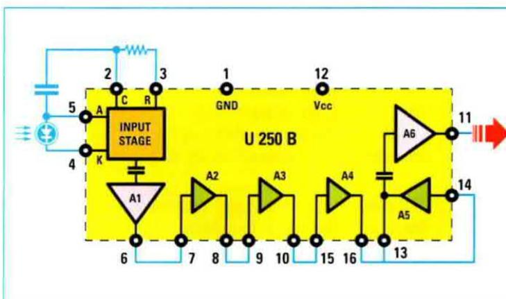
Fig.1 Schema a blocchi del rivelatore U.250/B e a destra le connessioni viste da sopra. Il segnale captato dal diodo FD1 viene amplificato, poi filtrato dagli stadi A2-A3-A4-A5 e quindi prelevato dal piedino 11 per essere trasferito su IC3 (vedi fig.4).
