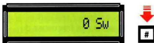
Fig.38 Per far avviare lo Sweep dovrete ripremere il tasto # e in questo modo vedrete apparire sul display la scritta "0 Sw".
