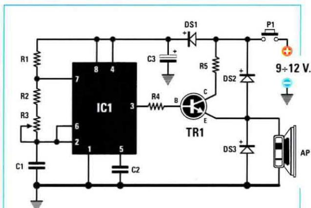
Fig.1 Schema elettrico del Buzzer.
