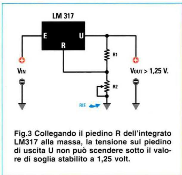
sima tensione in ingresso **meno 3-4 volt** fino ad un **minimo di 1,25 volt** attraverso il partitore formato da **R1** ed **R2**. Solitamente per **R2**, che è un **potenziometro**, si utilizza un valore ohmico di **4.700 ohm**, mentre la resistenza **R1** è da **220 ohm**.
