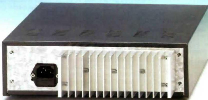
Fig.1 Il mobile metallico che abbiamo scelto per il circuito dell'alimentatore professionale ha un profilo semplice e lineare che ben si adatta a qualsiasi laboratorio. I potenziometri, situati sul pannello frontale visibile in alto a sinistra, vi consentono di scegliere il valore di tensione in uscita e di dosare la corrente massima erogata. Sul pannello posteriore (vedi qui sopra) vanno montate la presa di rete e l'aletta di raffreddamento.
