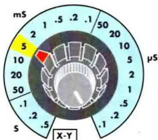
Fig.18 Se con la manopola del Time/div. posizionata sempre sui 5 mS misurate una tensione alternata raddrizzata da 4 diodi posti a Ponte, sullo schermo appariranno le sole semionde positive distanziate di 2 quadretti, perchè la frequenza pulsante risulta di 100 Hz. Sull'uscita applicate una R1 di carico da 1.000 ohm.
