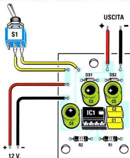
Fig.2 Schema pratico di montaggio del circuito in fig.1. Nel montaggio controllate che la fascia di riferimento dei diodi DS1-DS2 risulti rivolta verso sinistra.
