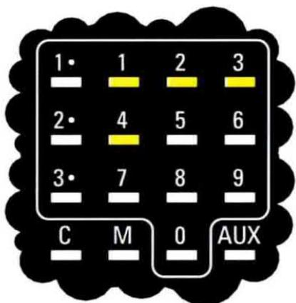
Fig.6 Per eccitare e diseccitare i Relè 1 e Relè 2 dovete premere i tasti 1-2-3-4 che nel disegno appaiono di colore Giallo. Premendo il tasto 1, ecciterete il Relè 1, premendo il tasto 2 lo disecciterete. Premendo il tasto 3 ecciterete il Relè 2, premendo il tasto 4 lo disecciterete. A relè eccitato si accenderà il Diodo Led posto in parallelo alla bobina (vedi fig.4).
