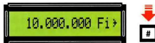
Fig.41 Per cambiare frequenza premete "3 volte" il tasto Mode in modo che appaia "0 Fi" (vedi fig.34) poi scrivete 10.000.000.
