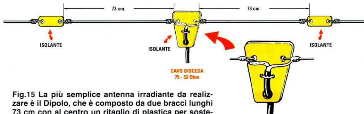
**Fig.15** La più semplice antenna irradiante da realizzare è il Dipolo, che è composto da due bracci lunghi 73 cm con al centro un ritaglio di plastica per sostenere il cavo coassiale che giunge dal Lineare.
