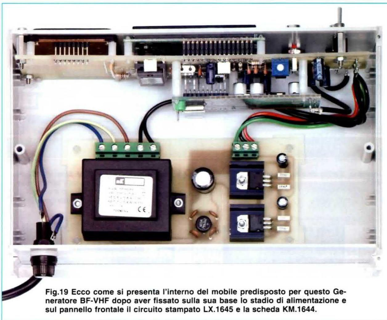
Fig.19 Ecco come si presenta l'interno del mobile predisposto per questo Generatore BF-VHF dopo aver fissato sulla sua base lo stadio di alimentazione e sul pannello frontale il circuito stampato LX.1645 e la scheda KM.1644.
