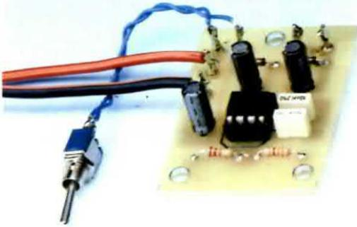
Utilizzando lo schema riportato in fig.1 è possibile prelevare in uscita una tensione maggiore rispetto al valore di alimentazione dell'integrato **NE.555**. Questo circuito può risultare utile per alimentare dei circuiti **preamplificatori** o eccitare dei piccoli **relè** che richiedano tensioni di **18-22 volt**.
