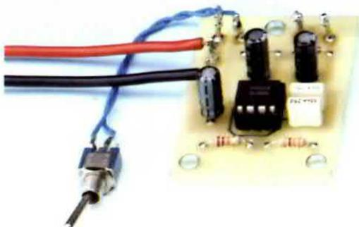
Può capitarvi di avere a disposizione una tensione **positiva** di 12 volt e di dover alimentare un circuito che richieda invece una tensione di polarità **negativa** che si aggiri sugli 8-9 volt.
