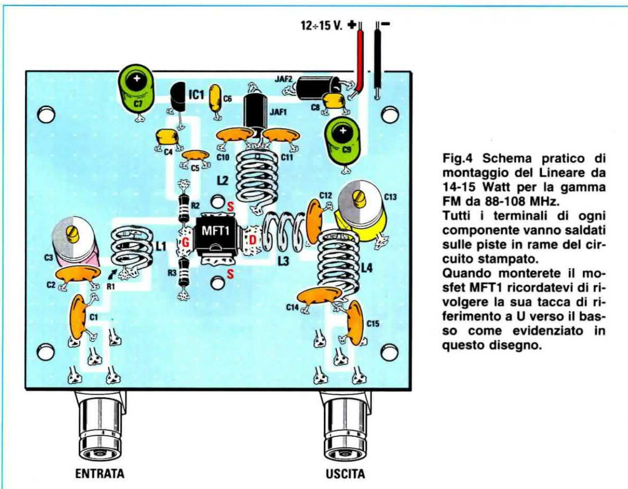
Fig.4 Schema pratico di montaggio del Lineare da 14-15 Watt per la gamma FM da 88-108 MHz. Tutti i terminali di ogni componente vanno saldati sulle piste in rame del circuito stampato. Quando monterete il mosfet MFT1 ricordatevi di rivolgere la sua tacca di riferimento a U verso il basso come evidenziato in questo disegno.
