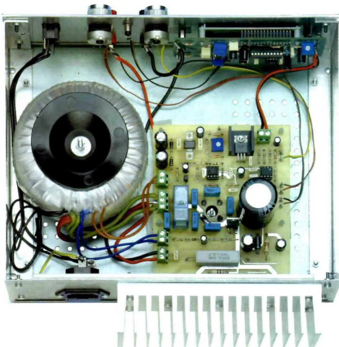
Fig.14 In questa foto l'interno del mobile, nel quale sono già stati collocati tutti i componenti, è riprodotto dal retro. Ciò vi consente di apprezzare l'esatta collocazione del voltmetro-ampereometro LX.1556 e degli altri componenti sul pannello frontale. Dedicate particolare cura al cablaggio, aiutandovi anche con lo schema riprodotto in fig.6.
