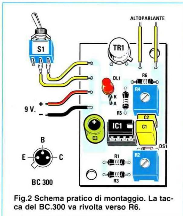
Fig.2 Schema pratico di montaggio. La tacca del BC.300 va rivolta verso R6.
