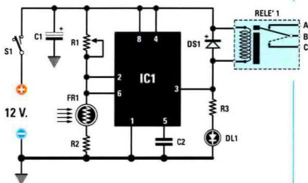
Fig.1 Schema elettrico dell'interruttore crepuscolare con fotoresistenza.
