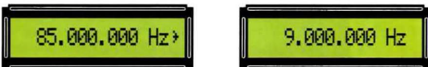
Fig.22 Se sul display appare 85.000.000 Hz > ma volete ottenere 9.000.000 Hz, basta scrivere questo numero e poi premere il tasto di conferma #. Se sulla destra di Hz non appare il segno >, dal Generatore uscirà la frequenza impostata precedentemente.
