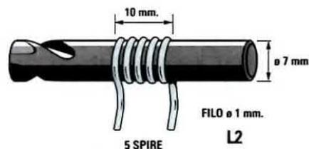
Fig.9 Per avvolgere la bobina L2 composta da 5 spire, dovrete utilizzare del filo di rame nudo da 1 mm, che avvolgerete su un supporto del diametro di 7 mm. Le spire vanno spaziate in modo da ottenere un solenoide lungo circa 10 mm.
