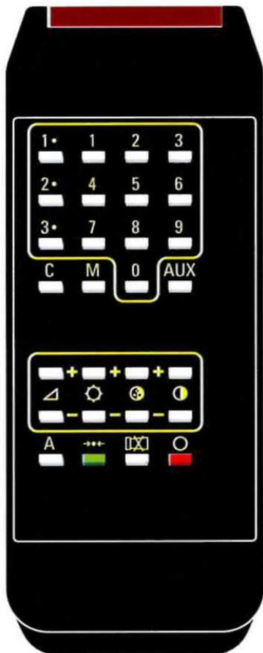
Fig.2 Prospetto del telecomando a raggi infrarossi utilizzato per il Light Controller. Poichè il telecomando è sprovvisto di pila da 9 Volt, dovrete provvedere voi ad inserirla nell'apposito vano aprendo lo sportellino posto sul retro.
