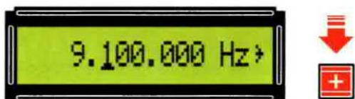
Fig.31 Come ormai vi sarà chiaro, premendo il tasto + la frequenza si incrementerà automaticamente di 100.000 Hz come evidenziato in figura.
