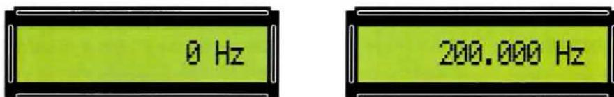
Fig.20 Per scegliere quale frequenza ottenere in uscita, dopo che sul Display sarà apparso lo 0 Hz iniziale, scrivete il valore desiderato in Hertz, quindi per ottenere 200 KHz digitate 200.000 Hz, poi premete il tasto # affinché, a destra, appaia il segno > di conferma.
