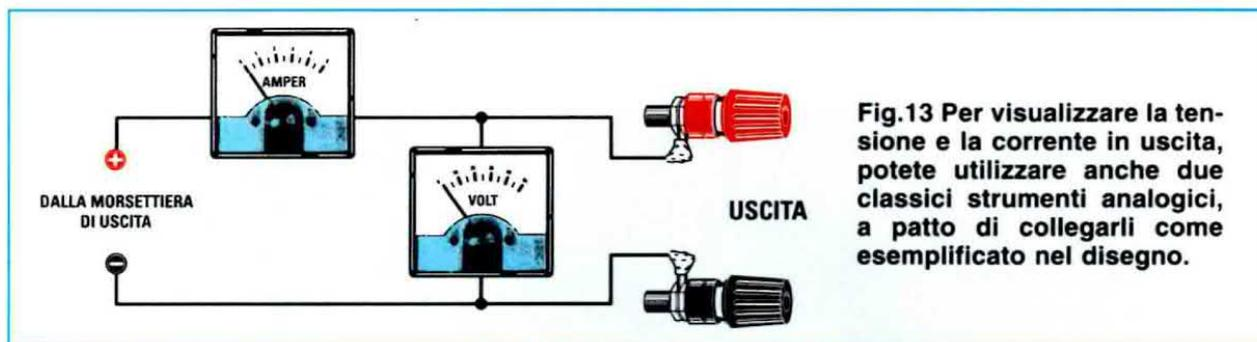
**Fig.13** Per visualizzare la tensione e la corrente in uscita, potete utilizzare anche due classici strumenti analogici, a patto di collegarli come esemplificato nel disegno.
