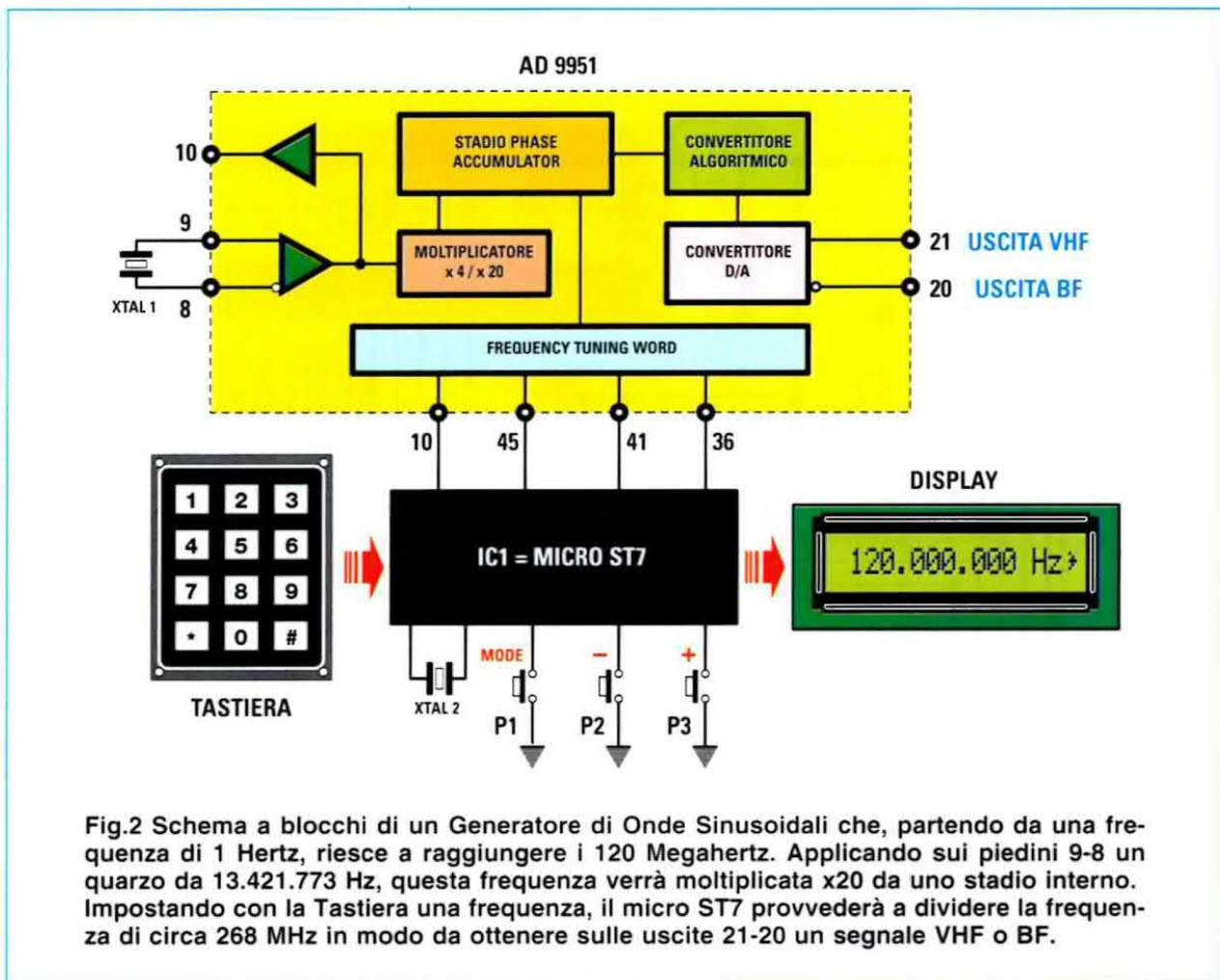
Fig.2 Schema a blocchi di un Generatore di Onde Sinusoidali che, partendo da una frequenza di 1 Hertz, riesce a raggiungere i 120 Megahertz. Applicando sui piedini 9-8 un quarzo da 13.421.773 Hz, questa frequenza verrà moltiplicata x20 da uno stadio interno. Impostando con la Tastiera una frequenza, il micro ST7 provvederà a dividere la frequenza di circa 268 MHz in modo da ottenere sulle uscite 21-20 un segnale VHF o BF.
