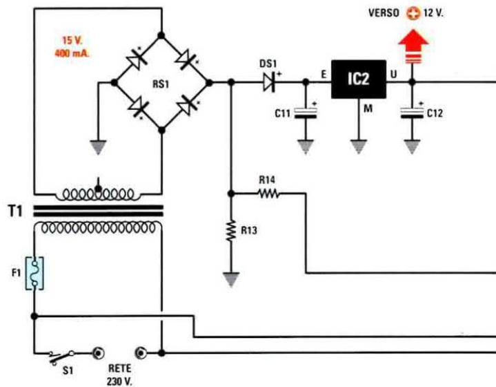
Fig.4 Schema elettrico del Light Controller che potrete utilizzare per eccitare e diseccitare, tramite il telecomando di fig.2, i Relè1 e Relè2 oppure per variare la luminosità delle lampade collegate alle uscite LP1-LP2-LP3.
