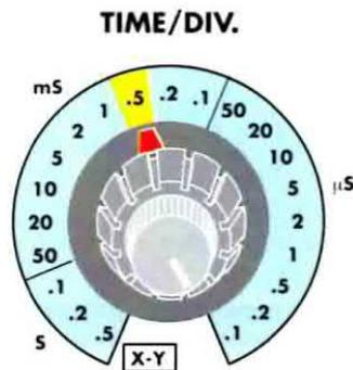
Fig.15 Se misurando un'onda notiamo che questa copre 4 quadretti più "3 tacche", che valgono 0,6 (vedi fig.14), con la manopola del Time/div. posizionata sugli 0,5 msec., il valore di questa frequenza risulterà esattamente pari a:  $1.000 : (0,5 \times 4,6) = 434,78 \text{ Hertz}$ .
