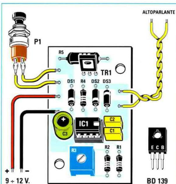
Fig.2 Schema pratico di montaggio. Il transistor **TR1** va montato rivolgendolo il suo lato metallico verso **IC1**.
