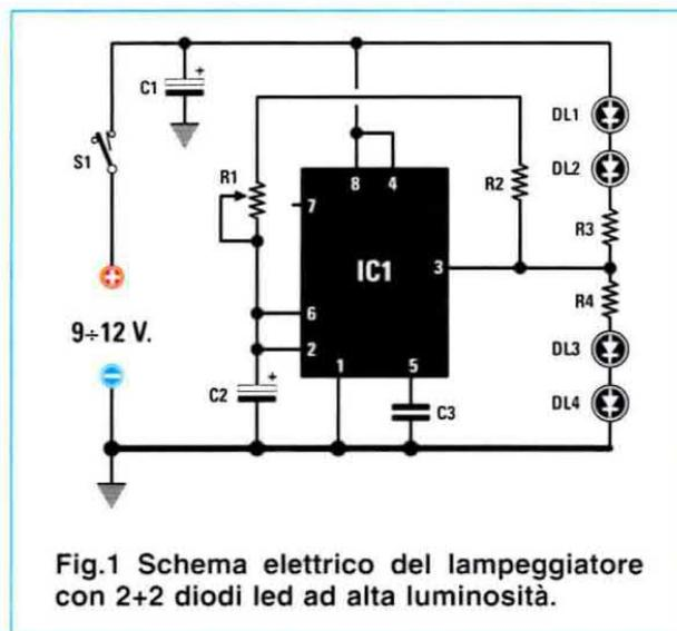
Fig.1 Schema elettrico del lampeggiatore con 2+2 diodi led ad alta luminosità.
