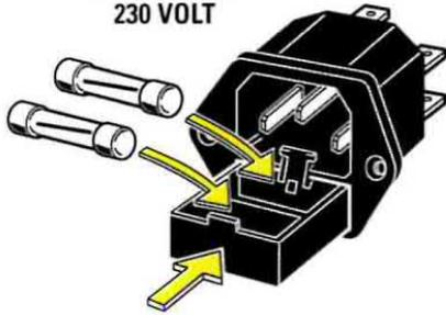
Nota: prima di montare la presa di rete sul pannello posteriore del mobile, controllate che al suo interno vi siano i fusibili da 3 ampere.
