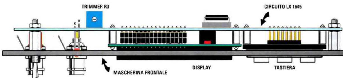
Fig.13 Disegno di come si presenta il circuito stampato LX.1645 dopo che lo avrete fissato stabilmente sulla mascherina frontale del mobile (vedi foto di fig.16). Il trimmer quadrato R3 visibile sul lato sinistro del Display, serve per regolare la sua luminosità.
