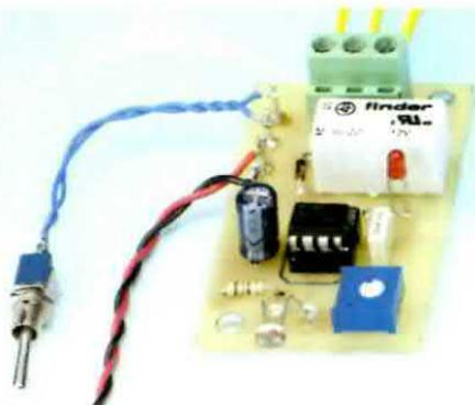
Utilizzando una **fotoresistenza** è possibile realizzare un semplice **Interruttore Crepuscolare** che fa **eccitare** un **relè** quando la luce diurna **scende** al disotto di un determinato valore e lo **diseccita** quando la luce ritorna sul suo valore.
