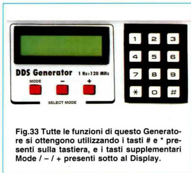
**Fig.33** Tutte le funzioni di questo Generatore si ottengono utilizzando i tasti **#** e **\*** presenti sulla tastiera, e i tasti supplementari **Mode / - / +** presenti sotto al Display.
