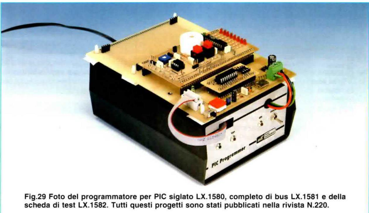
Fig.29 Foto del programmatore per PIC siglato LX.1580, completo di bus LX.1581 e della scheda di test LX.1582. Tutti questi progetti sono stati pubblicati nella rivista N.220.
