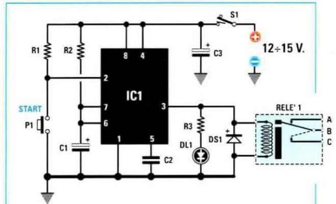
Fig.1 Schema elettrico del Timer per tempi fissi realizzato con un NE.555.
