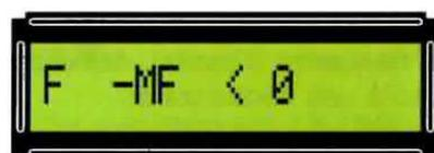
Fig.59 Se vi appare questa scritta significa che la Frequenza è minore della MF.
