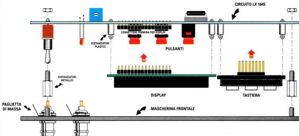
Fig.11 In questo disegno potete vedere come vanno applicati sul circuito stampato LX.1645, il Display e la Tastiera. Sul pannello frontale del mobile dovrete inserire i due connettori BNC, frapponendo tra il corpo e il dado di fissaggio una "paglietta di massa".
