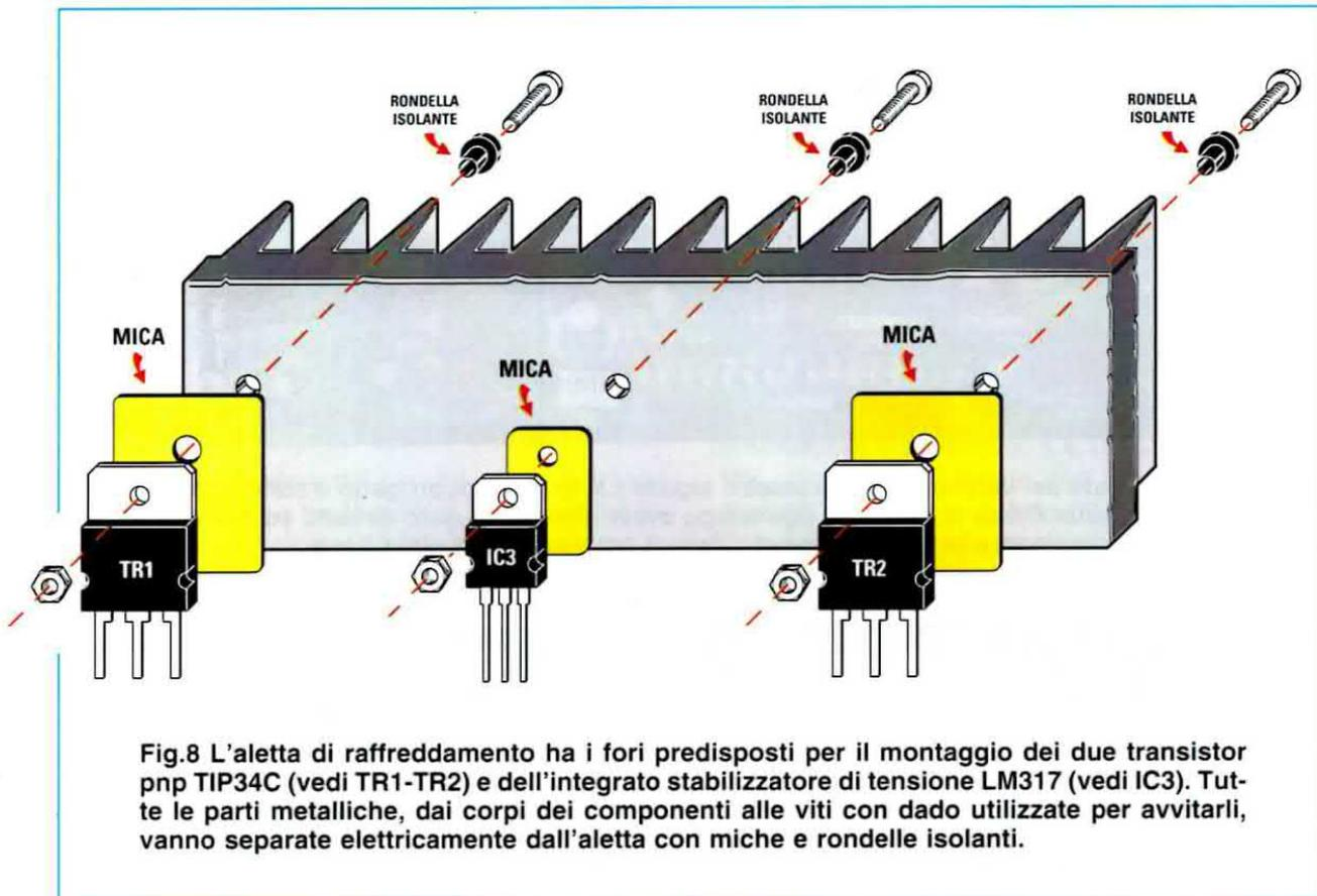
sentirà di sistemare e saldare alla giusta altezza il ponte raddrizzatore **RS1**, i transistor **TR1-TR2** e l'integrato **IC3**, evitando fili di collegamento che potrebbero causare delle cadute di tensione.
