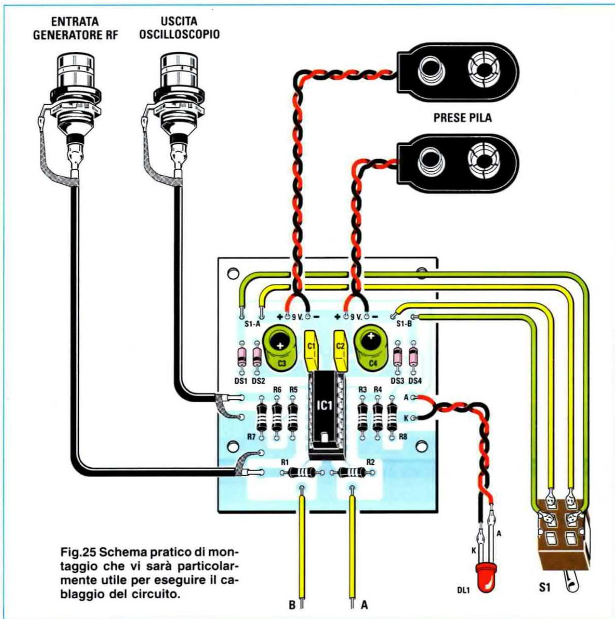
Fig.25 Schema pratico di montaggio che vi sarà particolarmente utile per eseguire il cablaggio del circuito.
