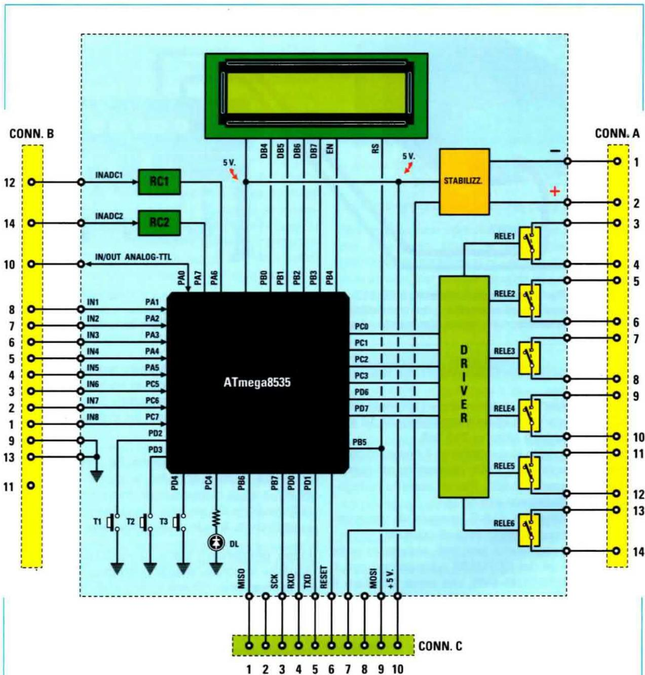
**Fig.8** Schema a blocchi del sistema embedded KM2107. Il micro ha ben 4 porte di comunicazione con l'esterno che consentono di gestire un display LCD a 2 righe 16 caratteri, sei relè, otto ingressi digitali binari, due ingressi ADC, un ingresso/uscita Analog/TTL, tre tasti ed un diodo led. Attraverso il connettore CONN.C è possibile programmare questo sistema con programmi scritti in basic utilizzando il software BASCOM-AVR.
