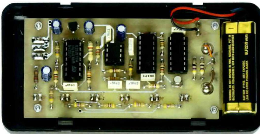
**Fig.7** In questa foto potete vedere come si presenta il Diode Speed Tester a montaggio ultimato. La pila di alimentazione viene posta nello spazio disponibile sul lato destro. Nota: il disegno serigrafico dei componenti viene realizzato sul circuito stampato solo dopo che questo è stato completamente forato.
