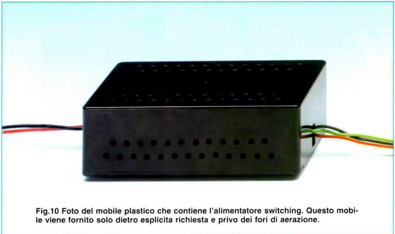
**Fig.10** Foto del mobile plastico che contiene l'alimentatore switching. Questo mobile viene fornito solo dietro esplicita richiesta e privo dei fori di aerazione.
