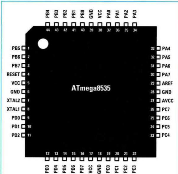
Fig.6 Connessioni viste da sopra del micro AtMega8535L. Sotto lo schema a blocchi.
