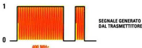
**Fig.5** Dopo essere stato codificato come indicato in fig.1, il segnale viene modulato dal trasmettitore su una portante a 400 MHz e quindi irradiato dall'antenna.
