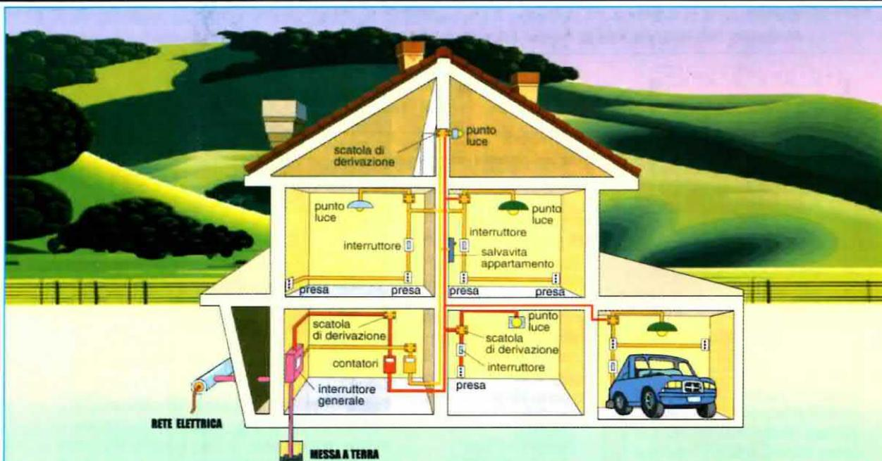
Fig.1 Tramite un telecomando ad onde convogliate è possibile attivare un dispositivo in qualunque punto della casa utilizzando l'impianto a 230 volt esistente.
