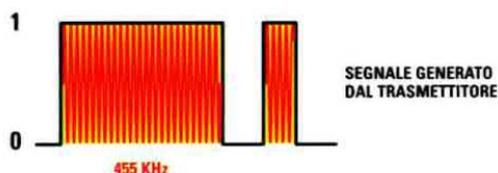
Fig.3 Dopo essere stato codificato, il segnale generato dal trasmettitore viene modulato sulla frequenza di 455 KHz e quindi immesso nella rete elettrica.
