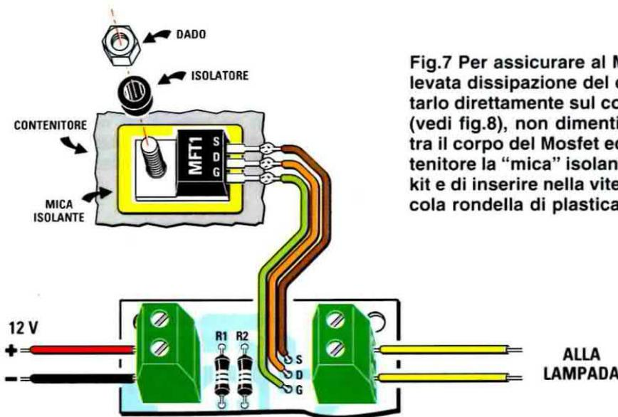
Fig.7 Per assicurare al Mosfet MFT1 una elevata dissipazione del calore, potete montarlo direttamente sul contenitore metallico (vedi fig.8), non dimenticando di applicare tra il corpo del Mosfet ed il metallo del contenitore la "mica" isolante che troverete nel kit e di inserire nella vite di fissaggio la piccola rondella di plastica.
