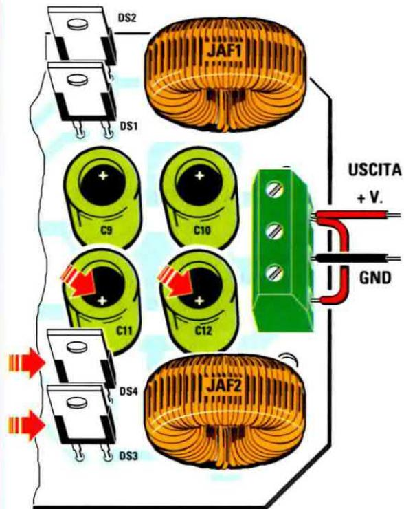
**Fig.9** Parte dello schema pratico di montaggio al quale dovete attenervi se volete un alimentatore switching con tensione singola. Non dimenticate di fare un ponte tra il 1° ed il 3° polo della morsettiere.
