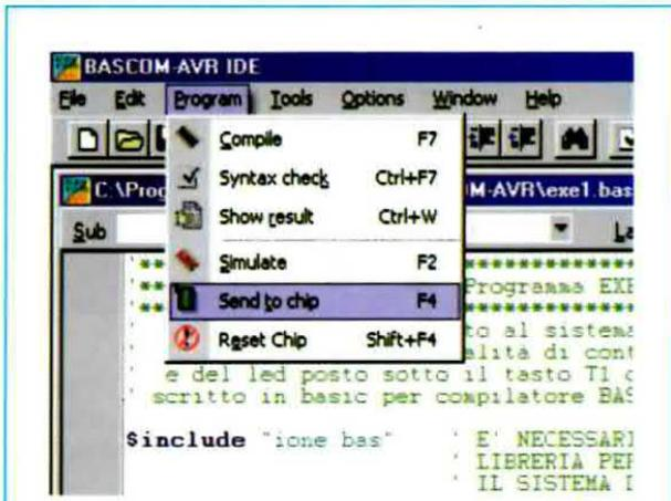
Fig.29 Se la compilazione non segnala alcun errore, potete programmare il micro. Sempre dalla voce di menu Program, selezionate con un clic Send to chip.
