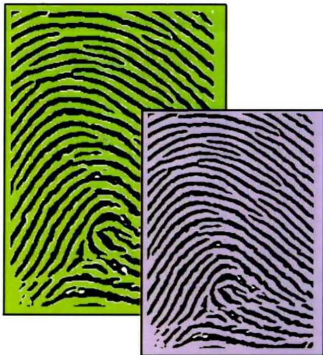
Fig.2 Disponendo di ben 400 sensori per ogni millimetro quadrato di superficie, il lettore è in grado di effettuare una lettura molto accurata delle linee papillari che costituiscono l'impronta digitale. L'impronta così rilevata viene poi ricostruita con un procedimento ad alta risoluzione e confrontata con quella precedentemente memorizzata garantendo una identificazione assolutamente sicura.
