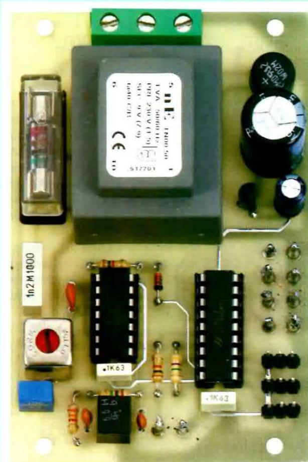
**Fig.11** Foto del circuito stampato del trasmettitore racchiuso nel mobile plastico che forniamo già forato e serigrafato. Sono ben visibili i collegamenti ai 4 pulsanti e alla tensione di rete. Notate anche, sulla sinistra del trasformatore, il fusibile già inserito nell'apposito portafusibile.
