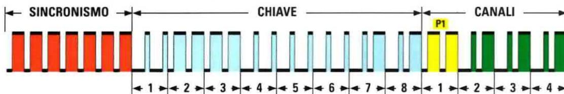
Fig.1 Il segnale generato dal trasmettitore è composto da un primo pacchetto di bit di sincronismo seguiti dagli 8 bit della chiave che consentono allo stadio ricevitore di identificare il trasmettitore. Da ultimo vengono trasmessi i 4 bit che indicano quale dei quattro pulsanti è stato premuto.
