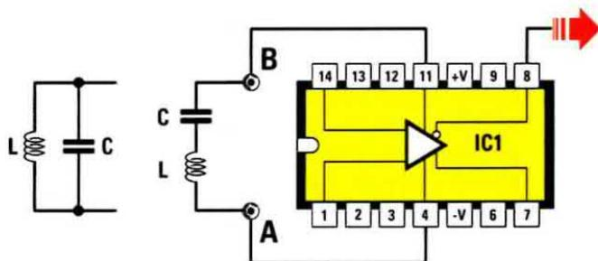
Fig.17 Utilizzando il nostro semplice accessorio potete determinare facilmente la frequenza di accordo di un circuito di sintonia L-C ed anche stabilire il valore della induttanza e della capacità.
