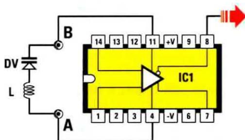
Fig.19 Se desiderate conoscere la capacità di un diodo Varicap, basterà collegarlo in serie ad una Induttanza L di valore conosciuto e poi procedere come se fosse un circuito L-C (vedi fig.18).
