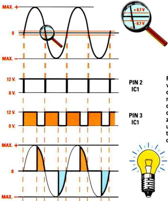
Fig.1 Il dimmer utilizza un circuito rivelatore di zero crossing, formato dai transistor TR1-TR2-TR3, sincronizzato con la sinusoide 12/24 Vac della tensione di ingresso. Ogniqualvolta la sinusoide passa per lo zero, sul piedino 2 di IC1 si genera un impulso negativo che abilita l'integrato NE555 (vedi IC1) configurato come monostabile.
