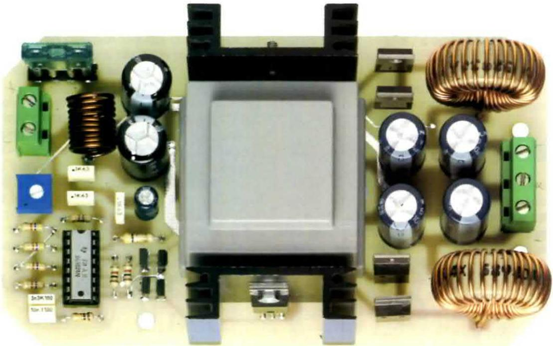
**Fig.6** Come si presenta il circuito dell'alimentatore a montaggio concluso. Come potete notare dalla fotografia, abbiamo potuto contenere le dimensioni delle alette di raffreddamento sulle quali sono avvitate i mosfet, perché, lavorando questi in commutazione, generano pochissimo calore e quindi non devono dissipare elevate potenze.
