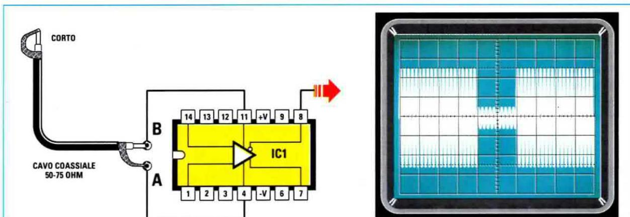
Fig.22 Se cortocircuiterete l'estremità del cavo coassiale noterete che variando la frequenza del Generatore RF dal suo minimo al suo massimo, si ottengono delle evidenti variazioni d'ampiezza su frequenze diverse, che da un massimo di 5 quadretti scenderanno bruscamente fino ad 1 quadretto.
