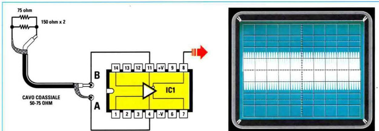
Fig.21 Se all'estremità di un cavo coassiale che ha una impedenza caratteristica di 50 o 75 ohm collegherete una resistenza di identico valore, noterete che variando la frequenza del Generatore RF dal suo minimo al suo massimo, l'ampiezza del segnale rimarrà costante sui 3 quadretti.
