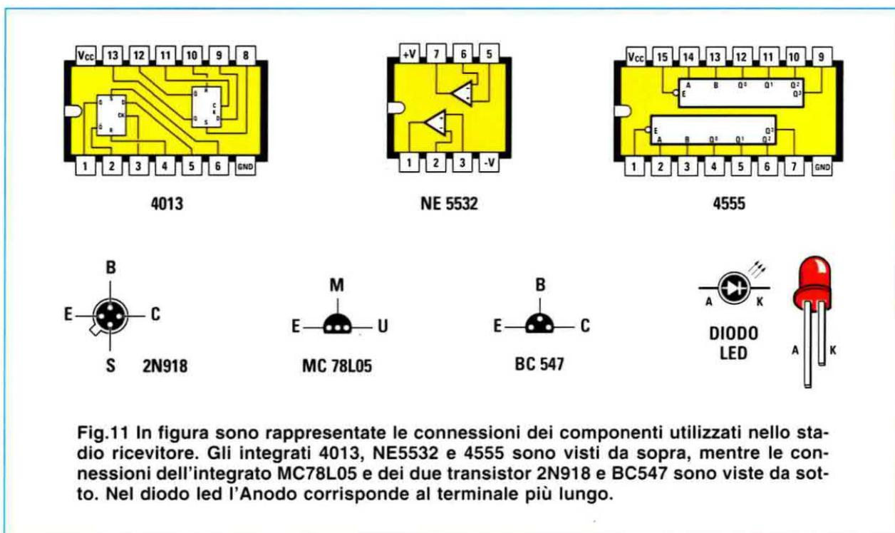
Fig.11 In figura sono rappresentate le connessioni dei componenti utilizzati nello stadio ricevitore. Gli integrati 4013, NE5532 e 4555 sono visti da sopra, mentre le connessioni dell'integrato MC78L05 e dei due transistor 2N918 e BC547 sono viste da sotto. Nel diodo led l'Anodo corrisponde al terminale più lungo.
