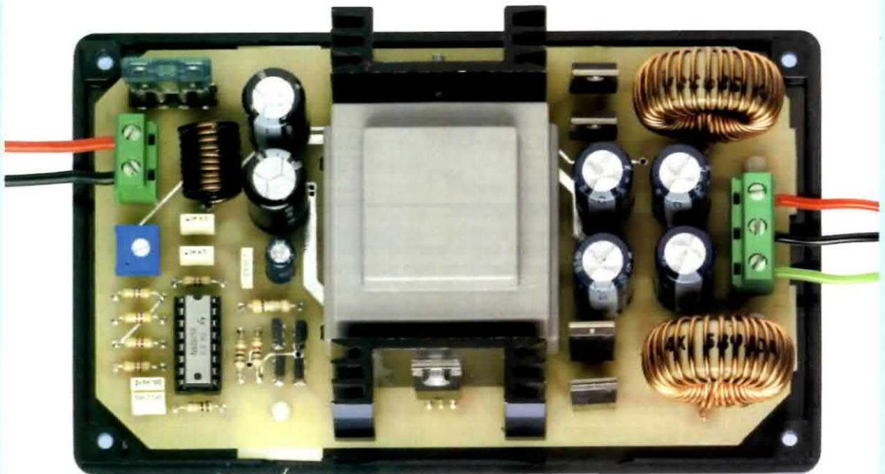
**Fig.7** Il mobile di plastica nera che vi segnaliamo è perfettamente dimensionato per contenere l'alimentatore switching. Il circuito va bloccato sul fondo adoperando i quattro distanziatori plastici con base autoadesiva inclusi nel kit. Prima di chiuderlo, dovete eseguire dei fori sul coperchio e sui fianchi per assicurare la ventilazione (vedi fig.10).
