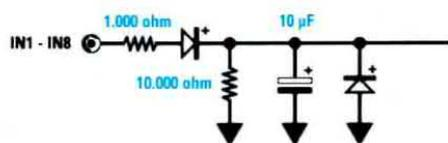
**Fig.4** Gli otto ingressi digitali del connettore **CONN.B** sono tutti di tipo **TTL** e, come semplificato in **fig.8**, ognuno di essi è connesso ad un particolare piedino del micro tramite questa rete di protezione.
