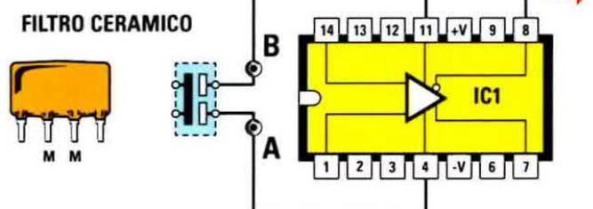
Fig.13 Per conoscere la frequenza di lavoro di un Filtro Ceramico provvisto di 4 piedini, basterà collegare i due terminali esterni agli ingressi A-B e ruotare la sintonia del Generatore RF fino a quando non incontrerete la sua frequenza di accordo, che farà bruscamente salire la sua ampiezza da 0,5 quadretti a circa 7 quadretti.
