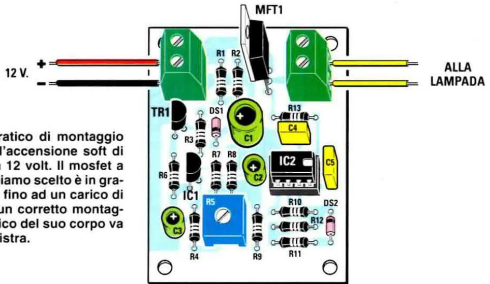
Fig.4 Schema pratico di montaggio del circuito per l'accensione soft di una lampadina a 12 volt. Il mosfet a canale P che abbiamo scelto è in grado di sopportare fino ad un carico di 10 ampere. Per un corretto montaggio, il lato metallico del suo corpo va rivolto verso sinistra.
