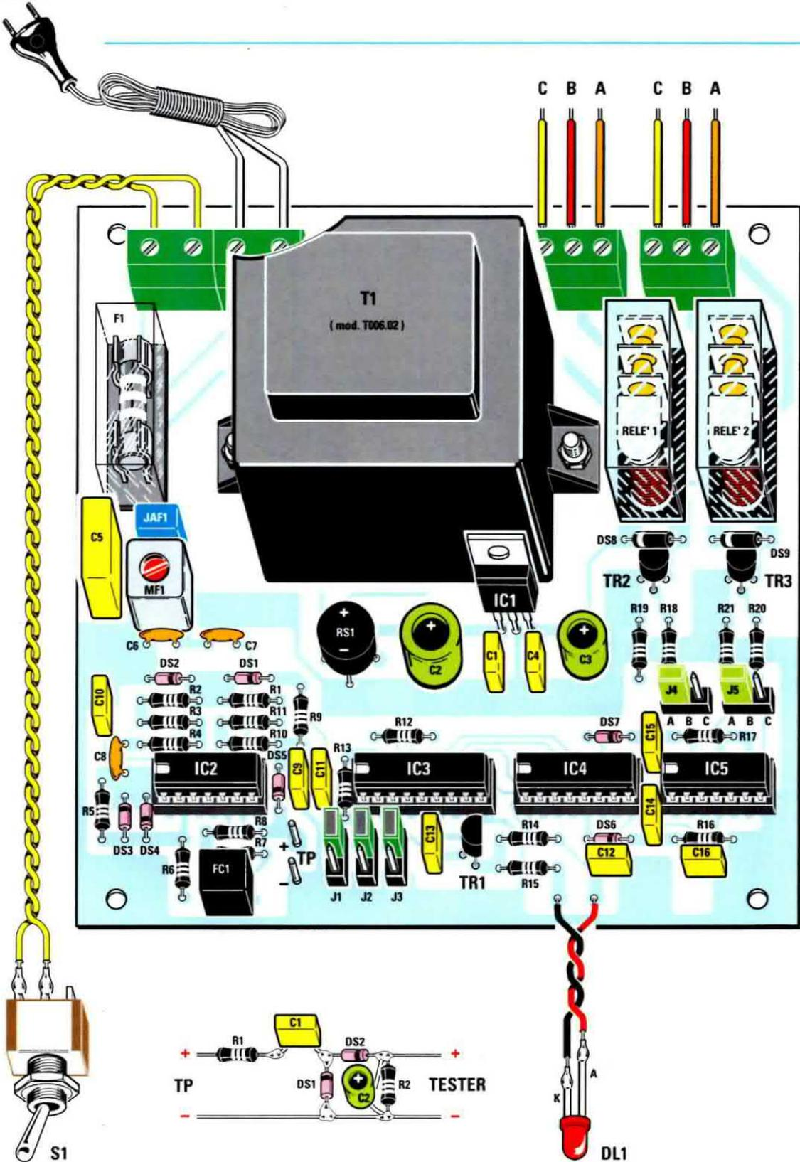
Fig.14 Disegno dello schema pratico di montaggio dello stadio ricevente. Qui sopra potete vedere la realizzazione pratica della piccola sonda che dovete utilizzare per effettuare la taratura del circuito: a questo scopo all'interno del blister dello stadio ricevente LX.1654 abbiamo provveduto ad inserire i pochi componenti necessari.
