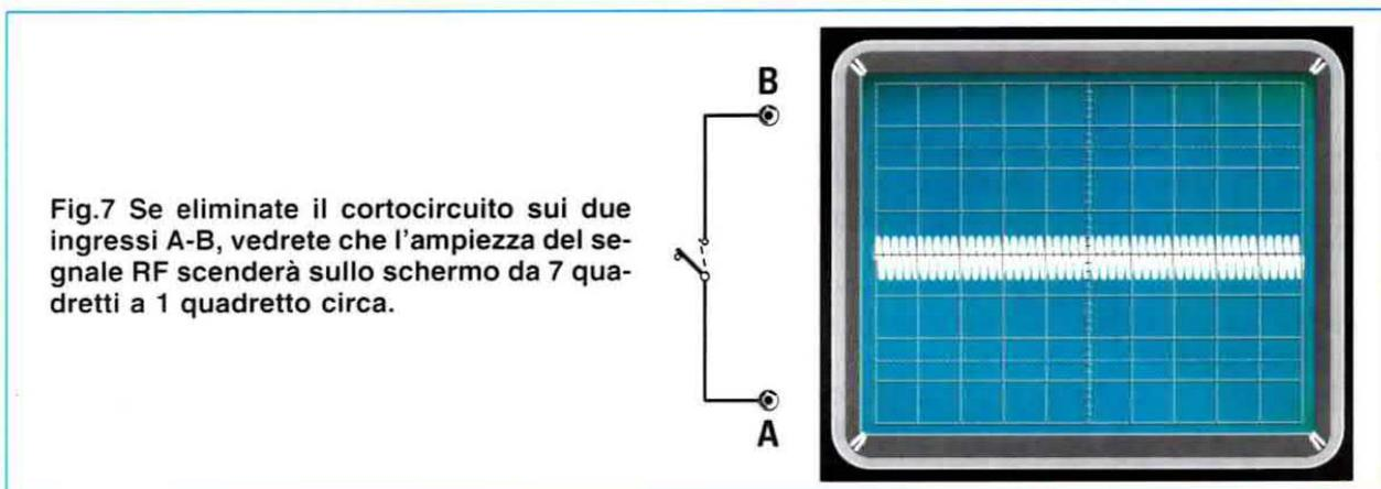
Fig.7 Se eliminate il cortocircuito sui due ingressi A-B, vedrete che l'ampiezza del segnale RF scenderà sullo schermo da 7 quadretti a 1 quadretto circa.
