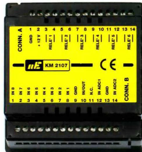
Fig.2 Il sistema embedded KM2107 visto dal lato dei due connettori.
