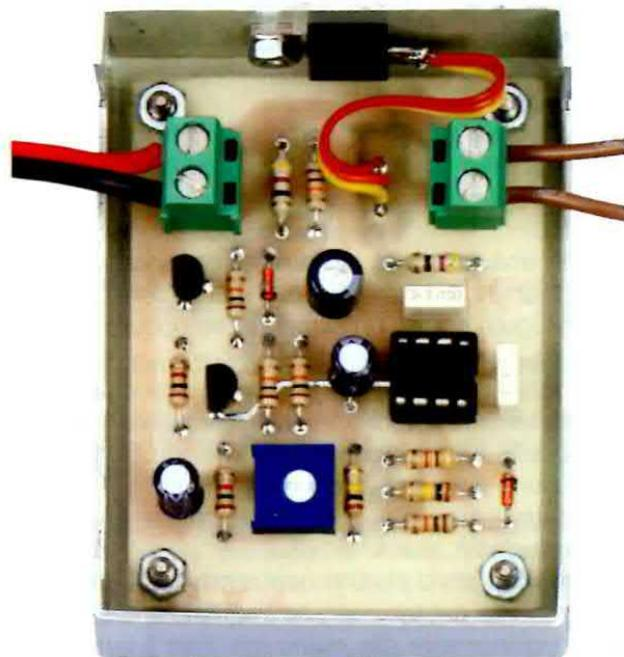
**Fig.9** La tensione dei 12 volt per alimentare questo circuito viene applicata alla morsettiere di sinistra e la lampadina da 12 volt alla morsettiere di destra.
