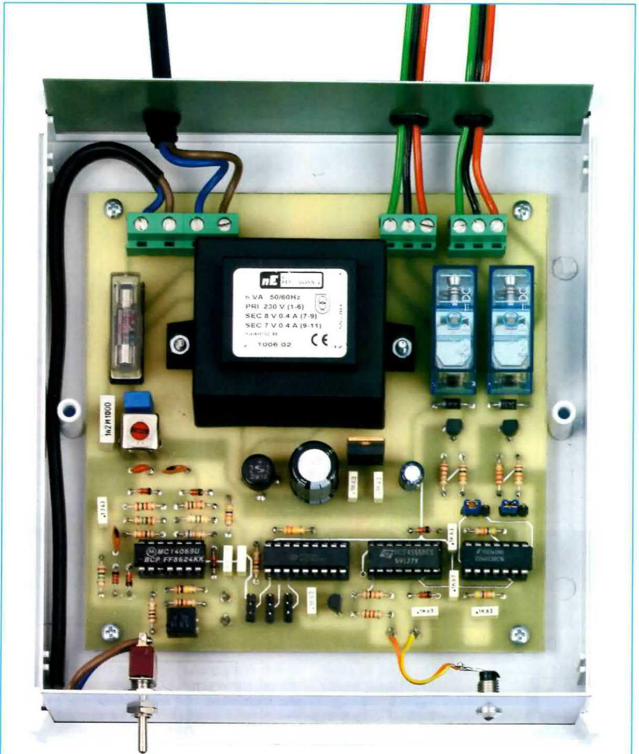
Fig.15 Foto del circuito stampato dello stadio ricevente. Poiché per questo circuito non abbiamo previsto un mobile particolare, vi ricordiamo che se sceglierete quello standard da noi suggerito (leggi testo) dovrete provvedere personalmente ad eseguire i fori per la fuoriuscita del deviatore a levetta, il diodo led e i cavi di collegamento alla rete dei 230 volt e quelli diretti al carico che desiderate pilotare.
