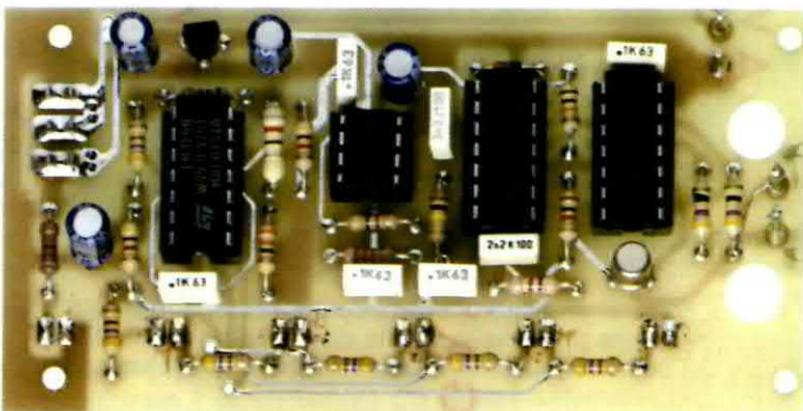
Fig.9 Foto del circuito del nostro Diode Speed Tester, riprodotto in forma grafica in fig.8.
