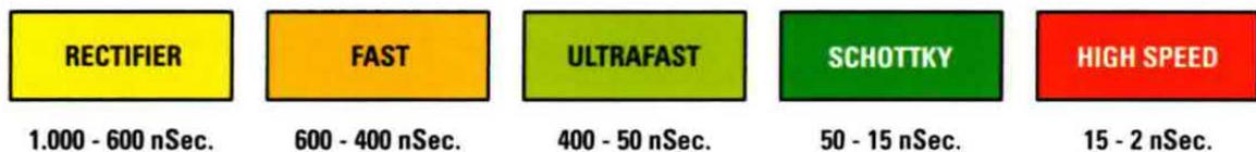
**Fig.1** I diodi meno veloci sono quelli che hanno una velocità compresa tra 1.000-600 nanosecondi e vengono utilizzati per raddrizzare la tensione di rete dei 50 Hertz, mentre i più veloci sono gli High Speed che possono raggiungere i 12-2 nanosecondi.
