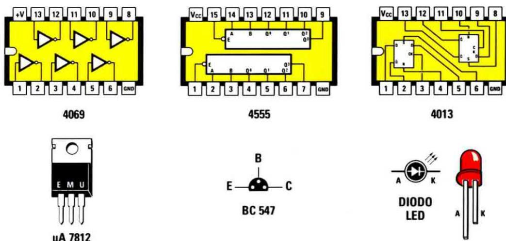
Fig.9 In alto, connessioni dei 3 C/Mos utilizzati nel circuito del ricevitore viste dall'alto e con la tacca di riferimento a U rivolta verso sinistra, in basso, connessioni dell'integrato uA.7812 viste frontalmente, del transistor BC547 viste da sotto e del diodo led. Come potete notare il terminale Anodo è riconoscibile per la maggiore lunghezza.
