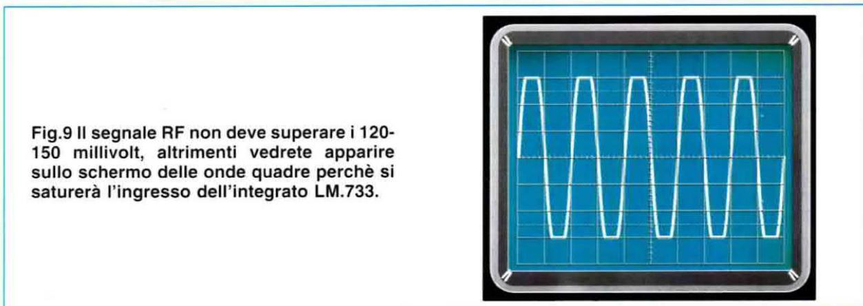
Fig.9 Il segnale RF non deve superare i 120-150 millivolt, altrimenti vedrete apparire sullo schermo delle onde quadre perchè si saturerà l'ingresso dell'integrato LM.733.
