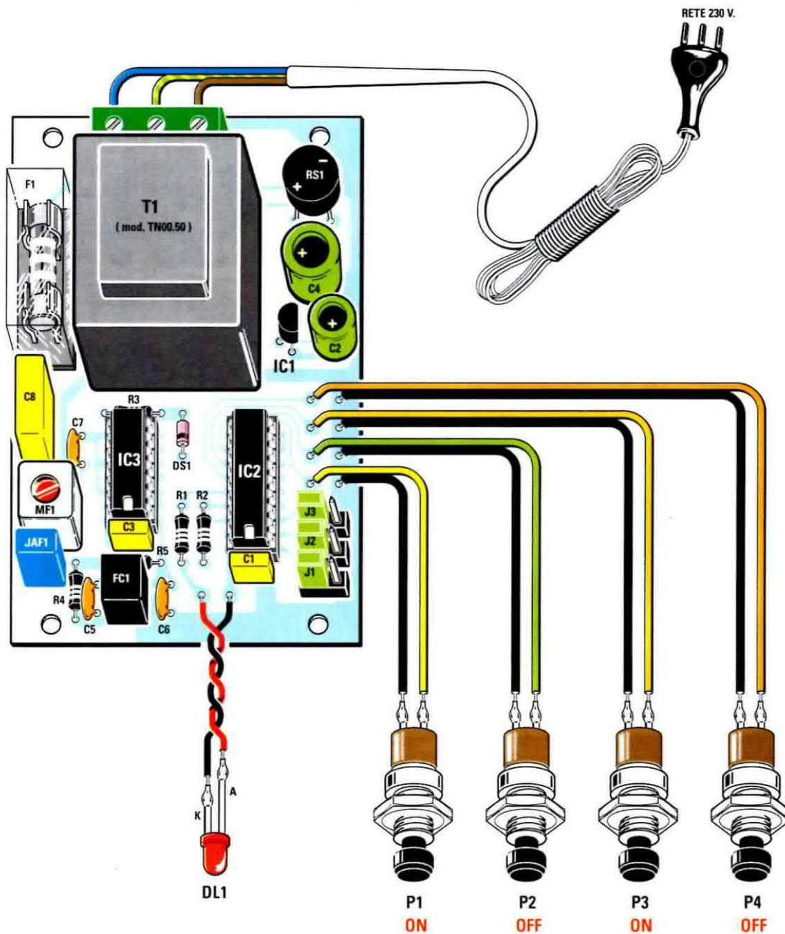
Fig.12 Schema pratico di montaggio dello stadio trasmettente. Sul circuito stampato, in basso a destra, sono presenti i 3 connettori J1-J2-J3 sui quali andranno inseriti i ponticelli che consentono di realizzare la combinazione della chiave. In posizione centrale il diodo led rosso DL1 che segnala l'accensione del circuito e, lateralmente, i 4 pulsanti P1, P2, P3 e P4 che permettono di attivare e disattivare il relè1 e il relè2.
