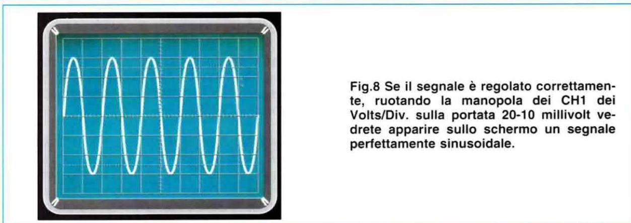
Fig.8 Se il segnale è regolato correttamente, ruotando la manopola dei CH1 dei Volts/Div. sulla portata 20-10 millivolt vedrete apparire sullo schermo un segnale perfettamente sinusoidale.
