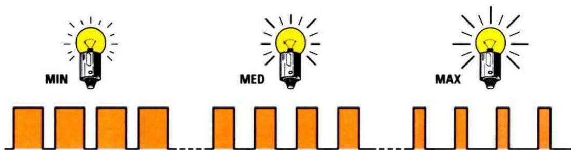
**Fig.1** Il disegno schematizza l'accensione di una lampadina in tre momenti. Come potete vedere, la sua luminosità è inversamente proporzionale al tempo in cui il duty cycle del segnale PWM permane a livello logico alto. In altre parole, la lampadina aumenta progressivamente la luminosità man mano che il livello logico alto del segnale PWM si restringe.
