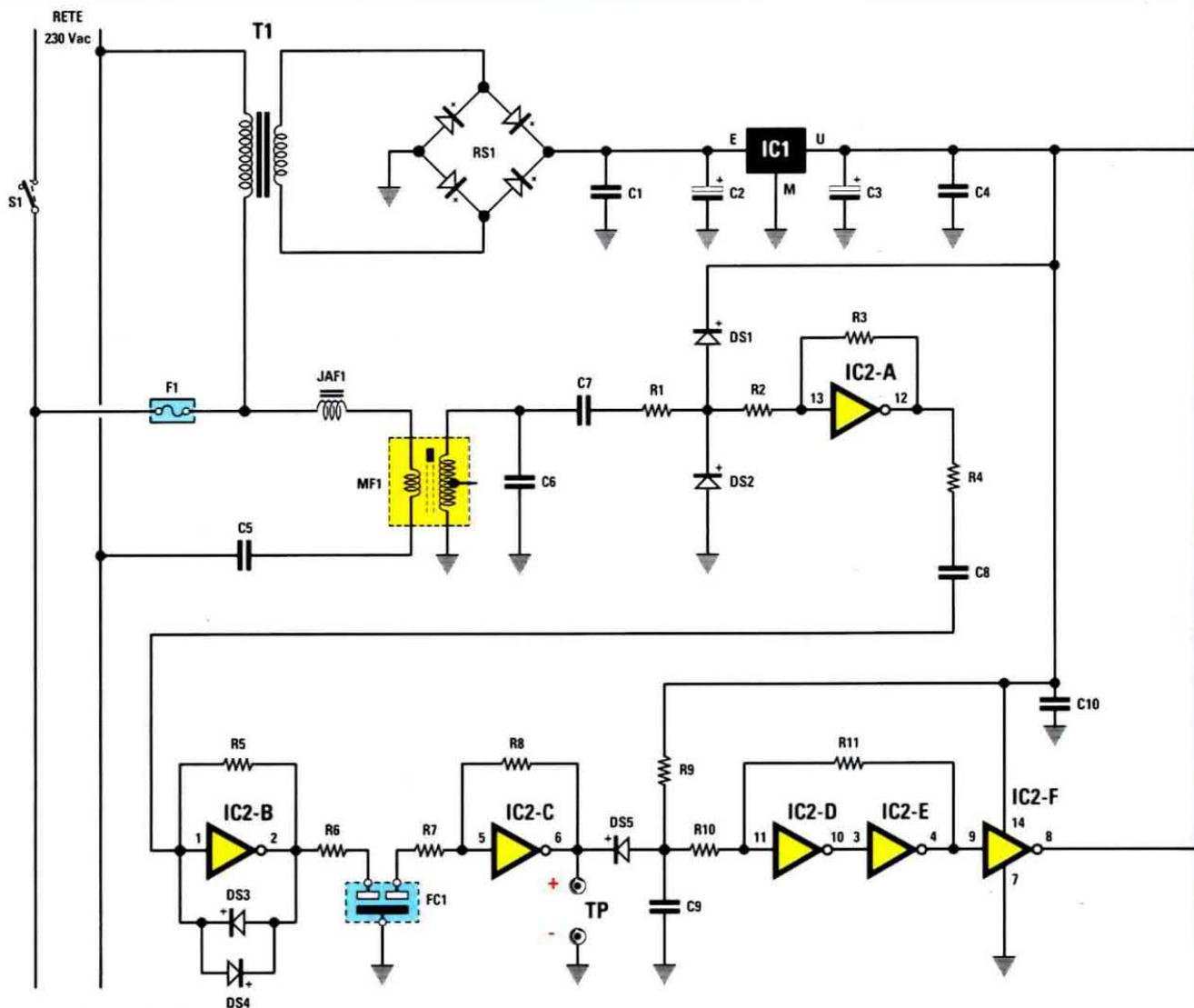
Fig.6 Schema elettrico del modulo ricevitore. Qui sopra è ben visibile il test point TP sul quale occorre prelevare il segnale da utilizzare nella procedura di taratura. Vi consigliamo di leggere in proposito il relativo paragrafo.
