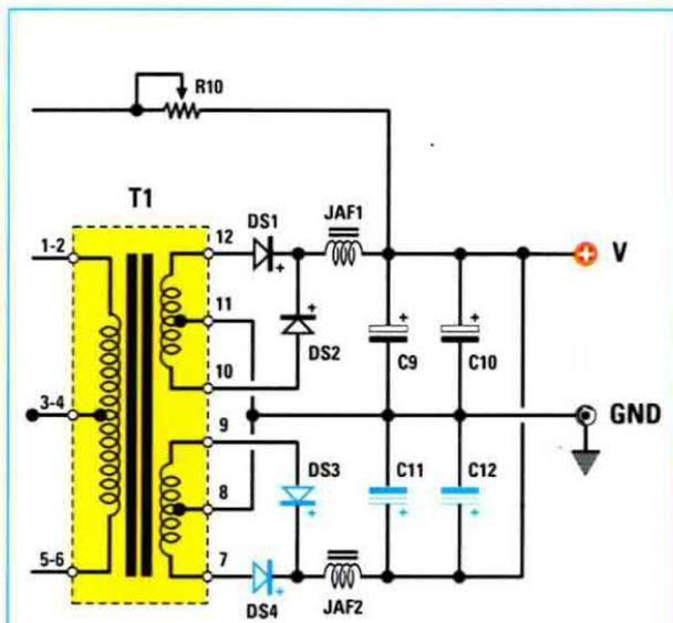
**Fig.8** Per adattare l'alimentatore switching di fig.3 in modo che fornisca in uscita una tensione singola compresa tra 5 e 32 volt, basta invertire la polarità dei componenti disegnati in blu: DS3-DS4 e C11-C12.
