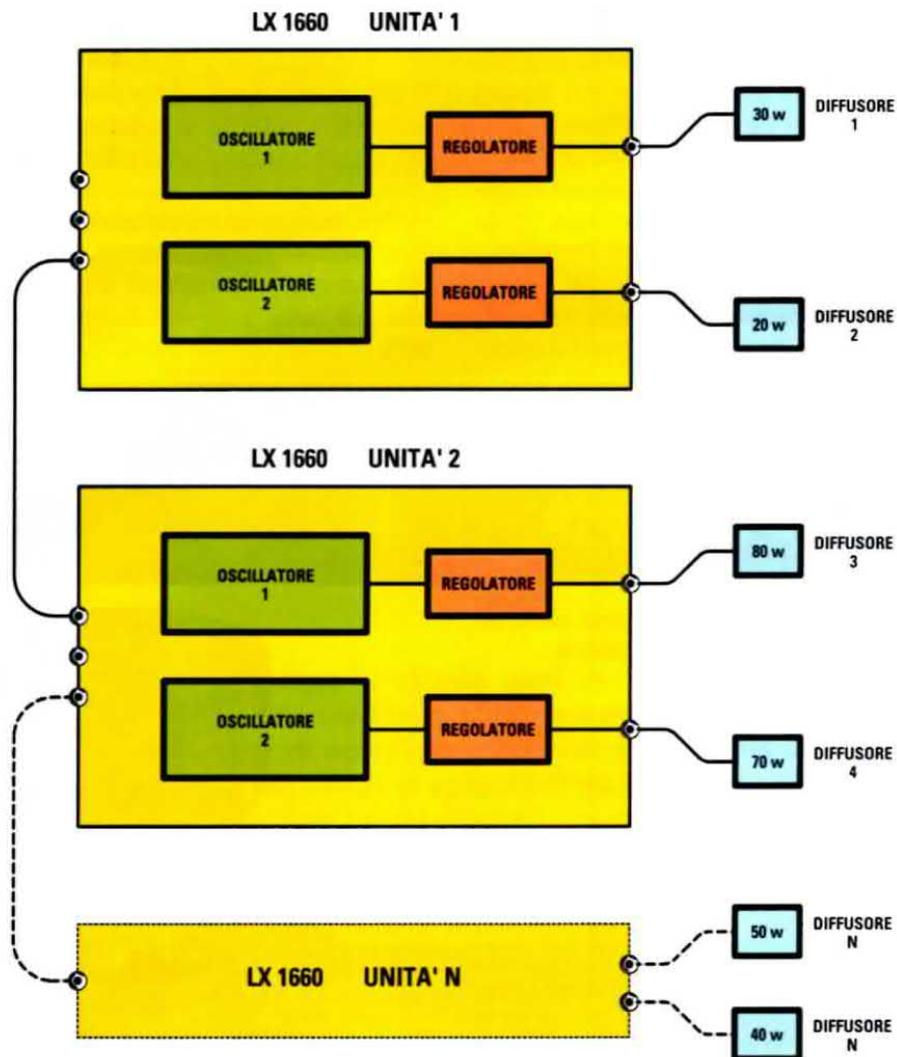
Fig.3 Il nostro generatore, è invece dotato di due oscillatori assolutamente indipendenti, che consentono di trattare contemporaneamente due punti del corpo in modo completamente diverso tra loro. Abbinando più generatori LX.1660 collegati tra loro in cascata, come rappresentato in figura, è possibile espandere a volontà il numero dei punti trattati.
