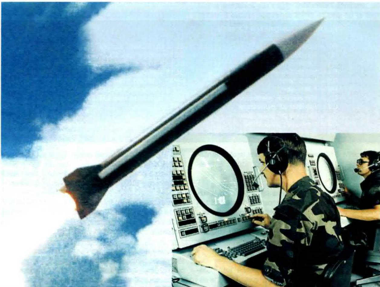
**Fig.17** Nelle ogive di tutti i missili aria-aria o terra-aria risultano installati dei sensibili sensori a raggi infrarossi in grado di pilotare i missili verso il calore generato dai reattori di un velivolo nemico. Per poterli evitare, furono studiate delle efficaci contromisure, come ad esempio le "palle di fuoco" chiamate anche "infrared flares".
