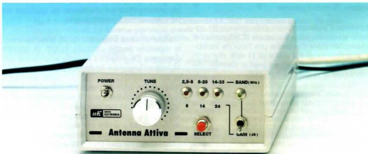
Fig.1 Ecco come si presenta il mobile della Centralina di Comando LX.1657 che andrà collocato vicino al ricevitore che si vuole sensibilizzare (vedi fig.2). Il deviatore a levetta S1 e il pulsante Select permettono di selezionare la Banda e il Guadagno.
