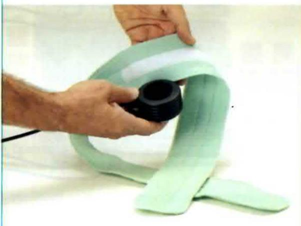
**Fig.28** Prima di posizionare il trasduttore sulla parte prescelta applicate sul suo corpo il ritaglio di velcro adesivo per effettuare il fissaggio alla fascia applicativa.
