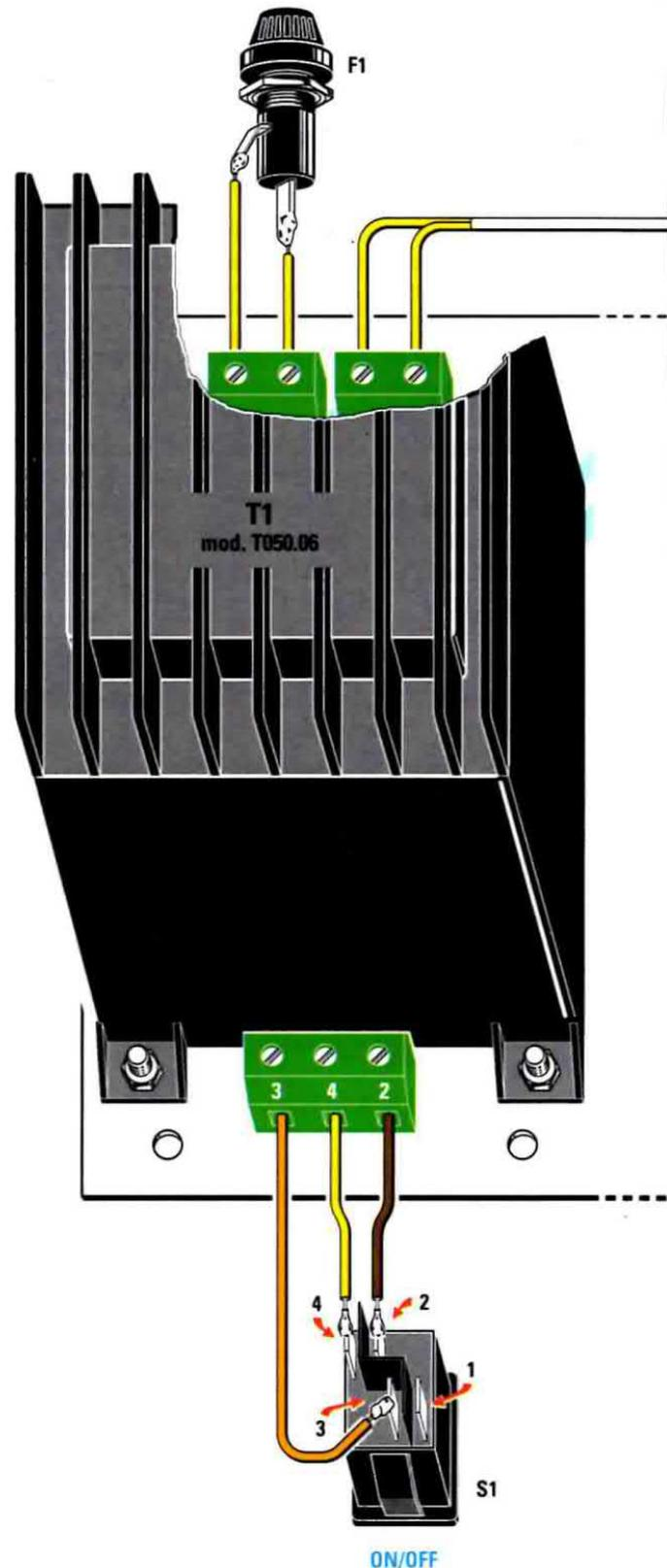
**Nota:** per non spezzare i terminali del trasformatore **T1**, prima di saldarlo bloccatelo allo stampato con 4 bulloni.
