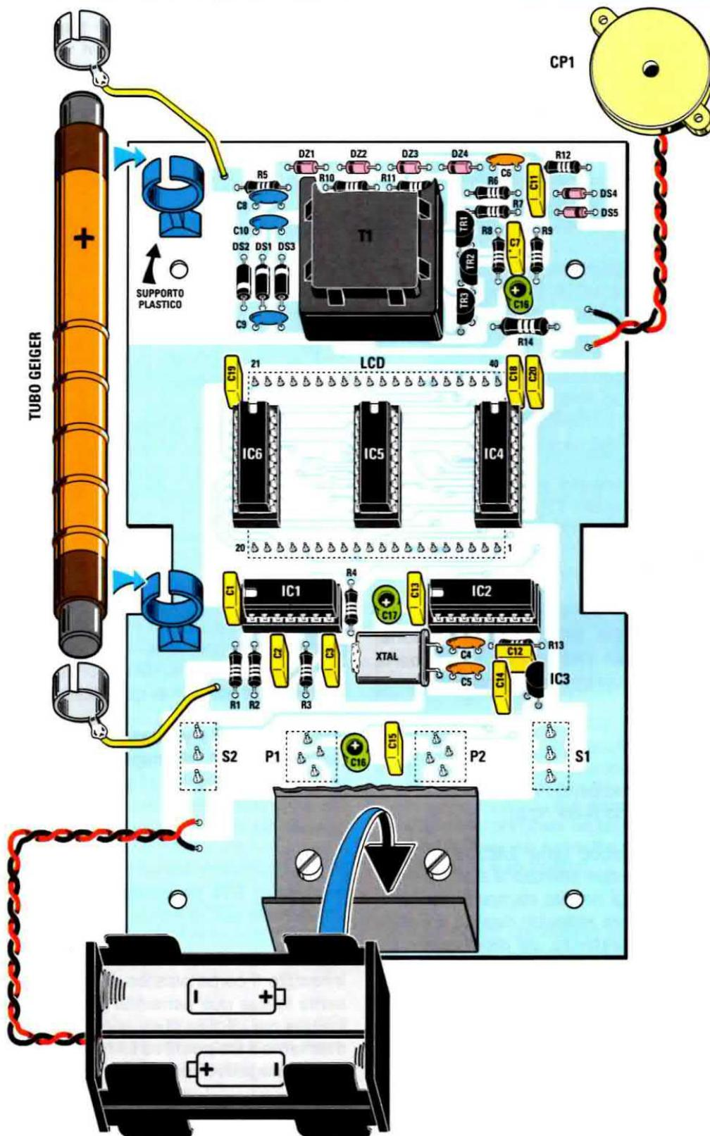
Fig.8 Schema pratico di montaggio del contatore Geiger visto dal lato dei componenti. Si noti la squadretta metallica a forma di U che servirà per inserire il supporto plastico contenente le 4 pile da 1,5 volt. Come potete notare in questo disegno, il terminale Positivo del tubo Geiger si riconosce perchè risulta più distanziato dai 5 anelli presenti sul suo corpo. Tale terminale va orientato verso l'ALTO mentre il terminale Negativo verso il BASSO.
