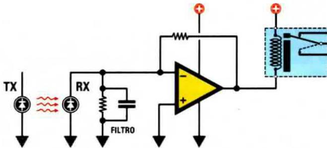
Fig.15 Per realizzare delle barriere a raggi infrarossi basta applicare di fronte al diodo ricevente un diodo trasmittente IR possibilmente modulato in BF. Chi, passando, interromperà questo fascio, farà eccitare il relè.
