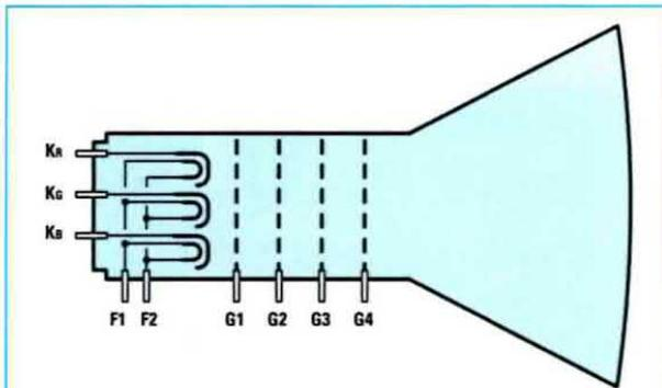
**Fig.11** Schema semplificato dei terminali da collegare al nostro rigeneratore. In questo caso si tratta di un tubo a colori perché ha tre catodi KR-KG-KB, uno per ognuno dei tre colori rosso-verde-blu.
