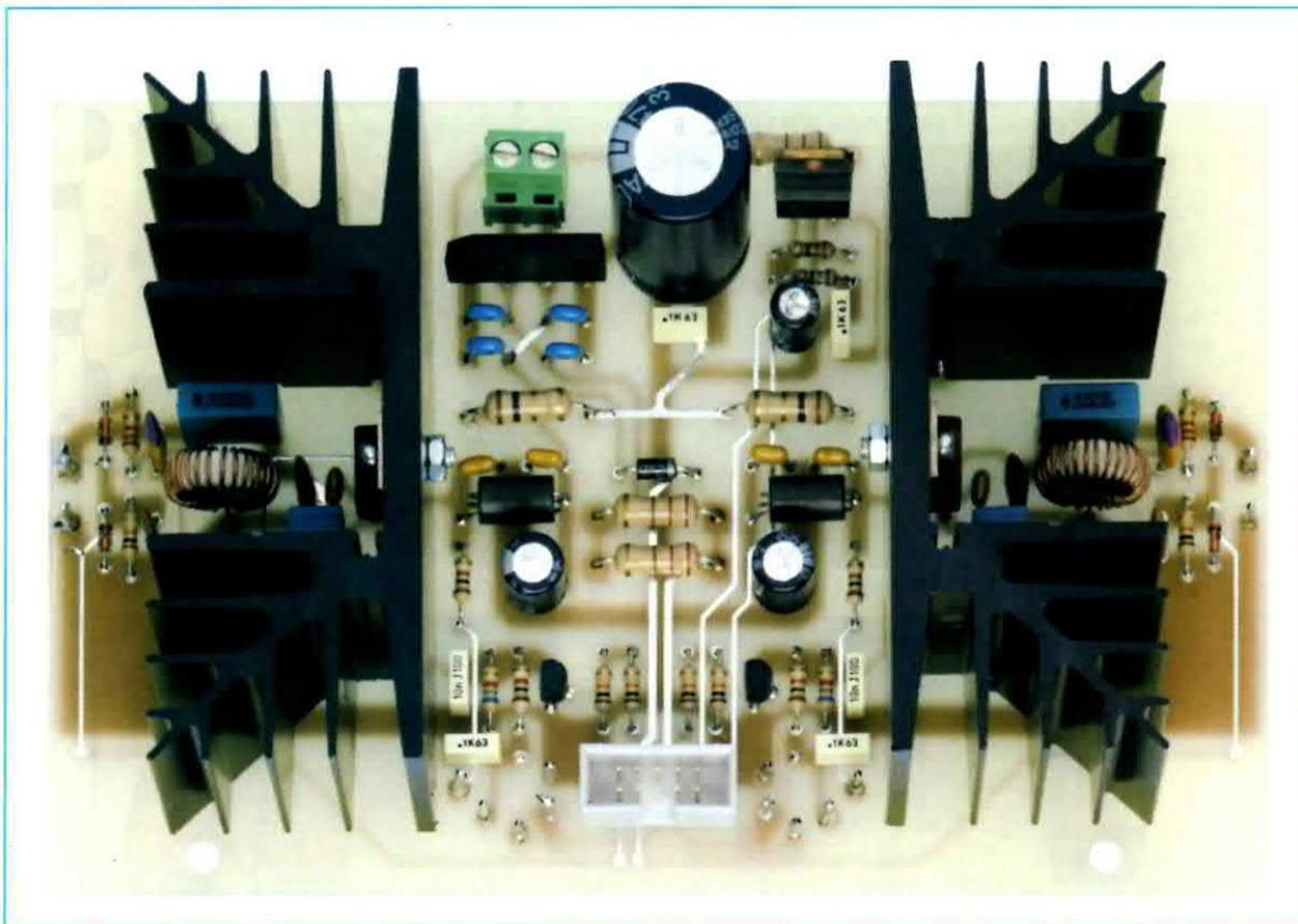
**Fig.15** In questa foto è riprodotta la scheda LX.1660 a montaggio ultimato. Come potete notare qui sono ben evidenti le due grosse alette che nel disegno di fig.13 apparivano soltanto tratteggiate. In basso osservate il connettore maschio CONN1 nel quale andrà innestato il connettore femmina della piattina che collega questo circuito stampato a quello del display siglato LX.1661 (vedi fig.16 in basso).
