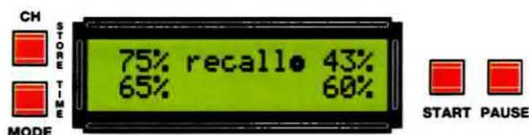
L'asterisco che segue la scritta **RECALL** si posiziona sul canale **CH1** ad indicare che dobbiamo eseguire la regolazione del potenziometro relativo a questo canale.
