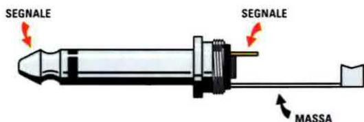
Fig.6 Negli spinotti Jack Mono da 6,3 mm vi sono due terminali. In quello più lungo viene collegata la calza di Schermo e nel più corto il filo in cui scorre il segnale BF.
