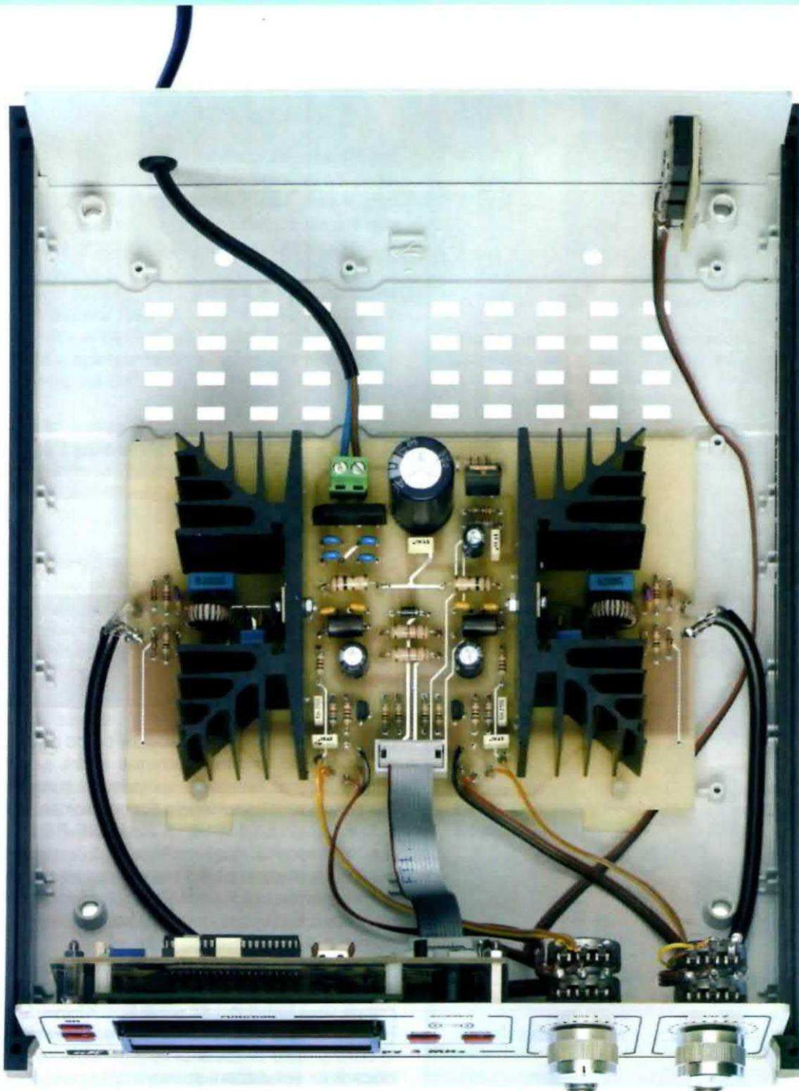
**Fig.23** In questa foto è ben visibile il cablaggio dei cavetti di collegamento tra il circuito stampato LX.1660 fissato sulla base del mobile, il circuito stampato del display LX.1661 e quello dei Jack LX.1661/B fissati rispettivamente sulla mascherina frontale e sulla mascherina posteriore del mobile.
