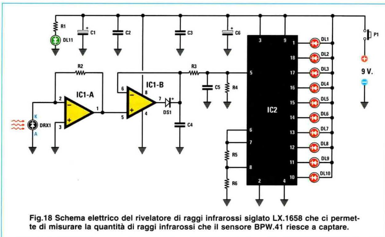
Fig.18 Schema elettrico del rivelatore di raggi infrarossi siglato LX.1658 che ci permette di misurare la quantità di raggi infrarossi che il sensore BPW.41 riesce a captare.
