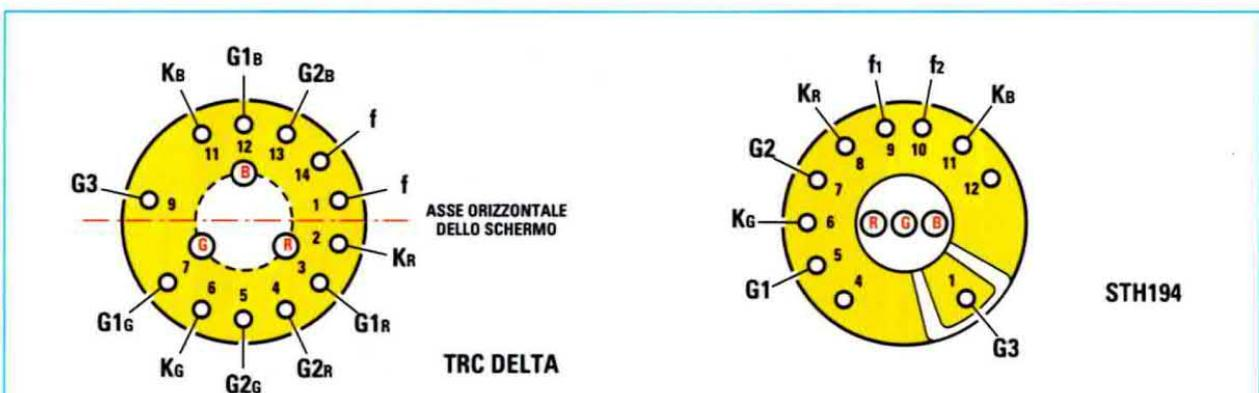
**Fig.13** Per rigenerare un tubo CRT senza correre il rischio di danneggiarlo in modo irreparabile, è indispensabile conoscere la sua piedinatura. Poiché, come abbiamo già detto, ogni casa costruttrice di televisori adotta propri tubi, per aiutarvi abbiamo riportato le connessioni di due "classici" tubi, utilizzati in molti apparecchi televisivi. Di solito sullo stampato che sorregge lo zoccolo, sono incisi i nomi dei terminali.
