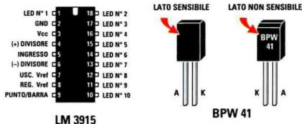
Fig.19 A sinistra le connessioni viste da sopra dell'integrato LM.3915. Precisiamo che il lato sensibile del sensore ricevente BPW.41 è quello sul quale **NON** appare nessuna scritta. Se inserite questo diodo sul circuito stampato in senso inverso, non potrà captare nessun segnale infrarosso.
