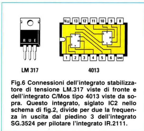
Fig.6 Connessioni dell'integrato stabilizzatore di tensione LM.317 viste di fronte e dell'integrato C/Mos tipo 4013 viste da sopra. Questo integrato, siglato IC2 nello schema di fig.2, divide per due la frequenza in uscita dal piedino 3 dell'integrato SG.3524 per pilotare l'integrato IR.2111.
