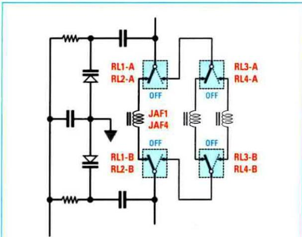
**Fig.5** Quando entrambi i relè **RL1** e **RL2** non sono eccitati, sia sull'ingresso che sull'uscita dei due Mosfet risultano collegate le impedenze di sintonia **JAF1** e **JAF4** da **22 microhenry**.
