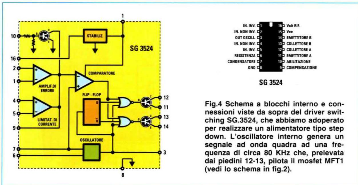
Fig.4 Schema a blocchi interno e connessioni viste da sopra del driver switching SG.3524, che abbiamo adoperato per realizzare un alimentatore tipo step down. L'oscillatore interno genera un segnale ad onda quadra ad una frequenza di circa 80 KHZ che, prelevata dai piedini 12-13, pilota il mosfet MFT1 (vedi lo schema in fig.2).
