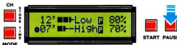
Premendo il tasto **START** il generatore riprenderà esattamente dal punto in cui è stato interrotto.
