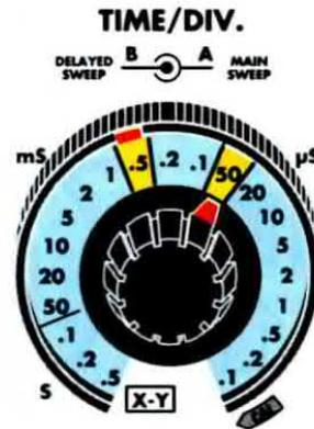
Fig.4 Il selettore **TIME/DIV** della doppia base dei tempi è composto da una ghiera esterna che agisce sulla base dei tempi **A** e da un selettore più interno che agisce sulla base dei tempi **B**. A seconda del modello di oscilloscopio, il selettore può essere realizzato in diversi modi.
