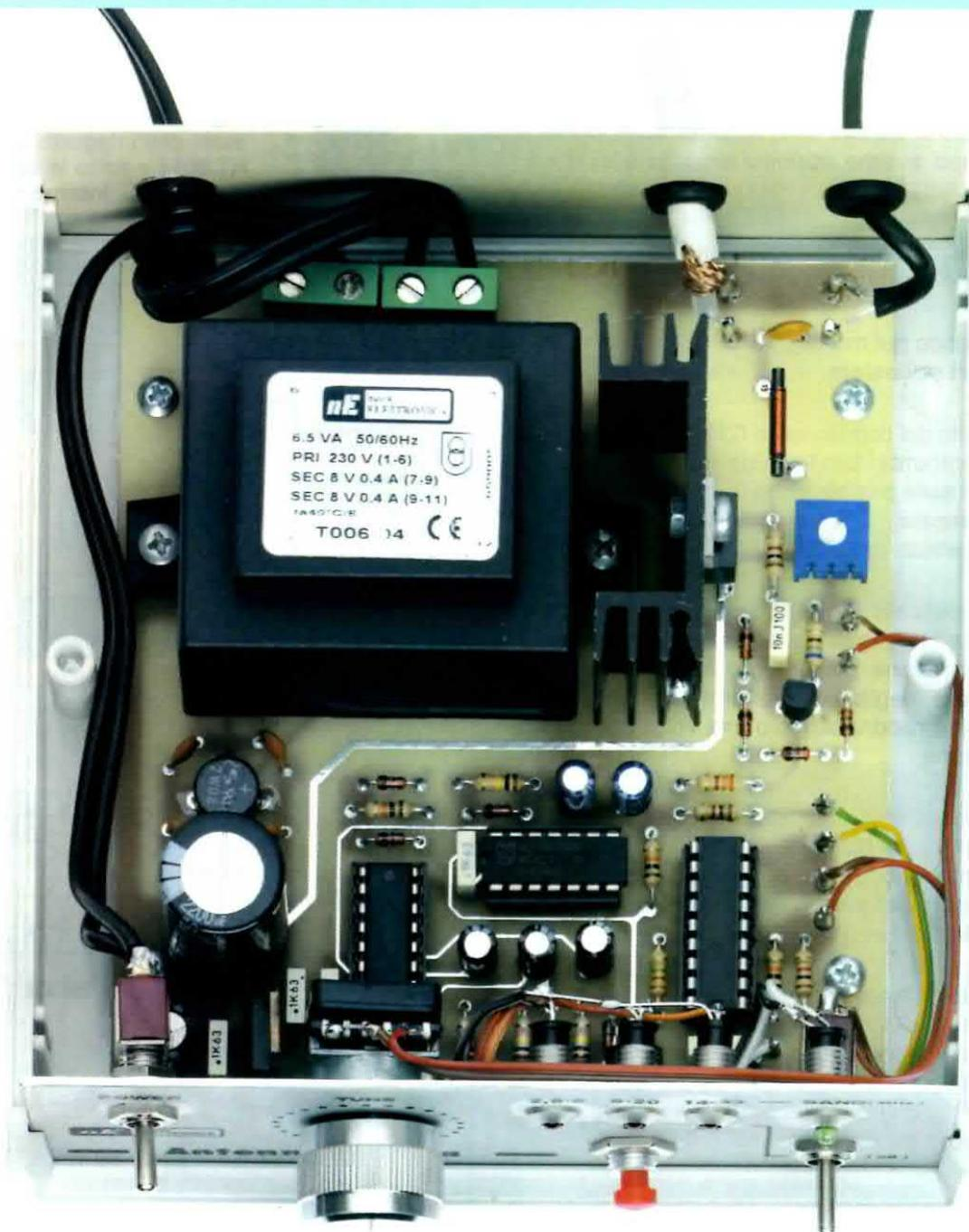
Fig.16 Foto della Centralina di comando siglata LX.1657 già fissata all'interno del mobile plastico. Il trimmer R3 posto in serie al potenziometro R1 (vedi fig.2) serve per variare il valore di tensione sui diodi Varicap, quindi a correggere la frequenza di sintonia.
