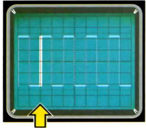
Fig.10 Ora ruotate la manopola interna del selettore Time/div sulla portata 5 microsecondi e vedrete la porzione di segnale evidenziata restringersi a circa 1 mm. di larghezza. Agendo sul potenziometro centrate nuovamente il fronte di salita del secondo picco.
