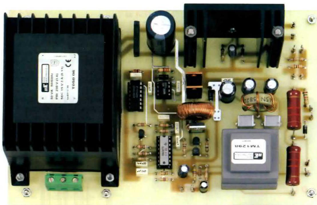
**Fig.9** Il circuito stampato del rigeneratore di tubi a raggi catodici a montaggio ultimato. In questa foto è chiaramente riconoscibile l'aletta di raffreddamento a forma di U, omessa nel disegno di fig.8, che permette all'integrato LM.317 di dissipare il calore prodotto durante il suo funzionamento. Quando inserite gli altri integrati nei loro zoccoli, rispettate la tacca di riferimento a forma di U che deve essere rivolta verso l'alto.
