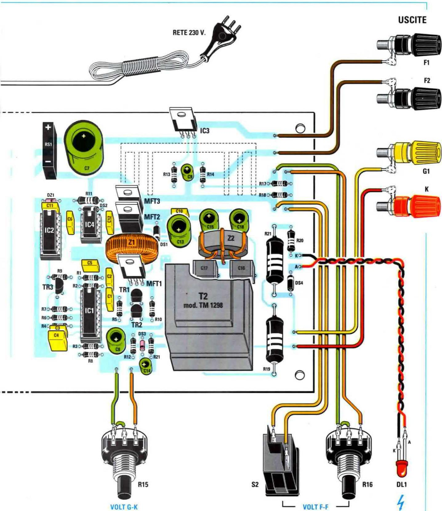
Fig.8 Schema pratico di montaggio del rigeneratore di tubi a raggi catodici. Per dissipare il calore prodotto, l'integrato stabilizzatore di tensione IC3 deve essere montato sopra un'aletta di raffreddamento che qui non è stata disegnata per non nascondere i componenti.
