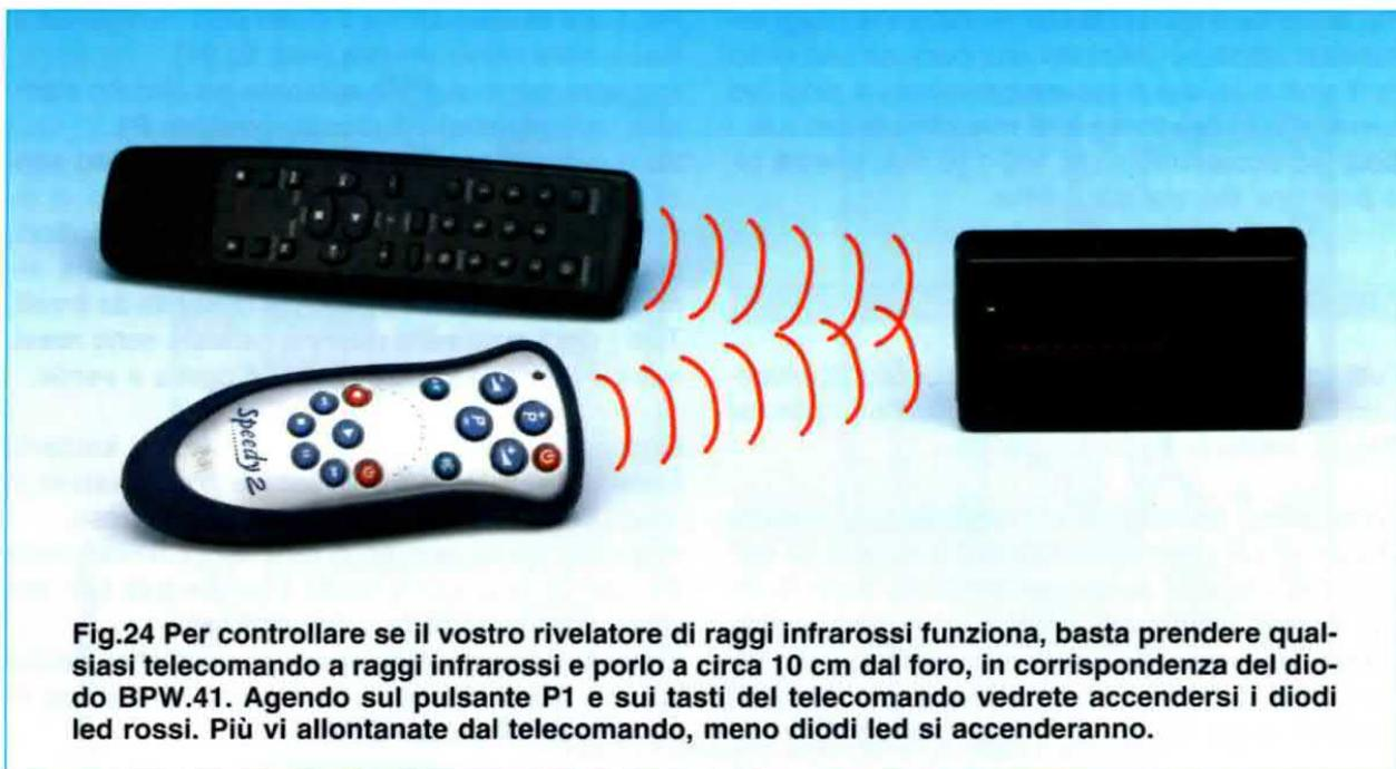
**Fig.24** Per controllare se il vostro rivelatore di raggi infrarossi funziona, basta prendere qualsiasi telecomando a raggi infrarossi e porlo a circa 10 cm dal foro, in corrispondenza del diodo BPW.41. Agendo sul pulsante P1 e sui tasti del telecomando vedrete accendersi i diodi led rossi. Più vi allontanate dal telecomando, meno diodi led si accenderanno.
