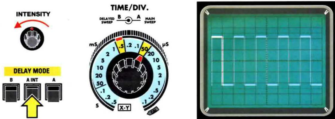
Fig.8 Dovrete quindi premere il tasto A+ INT del selettore Delay Mode e abbassare la manopola della luminosità in modo da evidenziare una porzione di segnale pari a circa un quadretto, che risulterà visibile per la sua maggiore luminosità.
