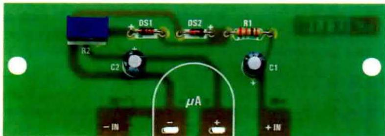
Fig.17 Foto del circuito con i componenti già montati. Lo strumentino va inserito nelle asole +/- dello stampato.
