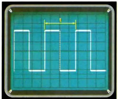
Fig.12 Il potenziometro multigiri consente di misurare con accuratezza la distanza che intercorre tra due picchi di un segnale, come rappresentato in figura. In questo modo sarete in grado di effettuare misure molto precise di frequenza.
