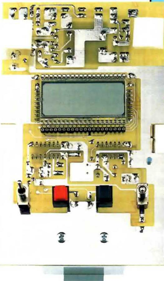
**Fig.7** Ecco come si presenta il circuito stampato di fig.6 dopo aver innestato nei due connettori femmina a 20 fori il display LCD. Non premete mai con le dita la parte centrale in vetro del display che potrebbe rompersi. Il lato opposto di questo circuito stampato, in cui dovrete montare tutti i componenti, è riprodotto nella figura successiva.
