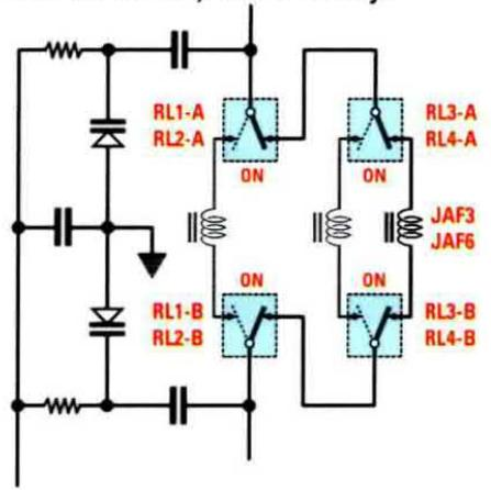
**Fig.7** Quando tutti i relè **RL1-RL2** e **RL3-RL4** sono eccitati, sia sull'ingresso che sull'uscita dei due Mosfet risultano collegate le impedenze di sintonia siglate **JAF3** e **JAF6** del valore di **0,82 microhenry**.
