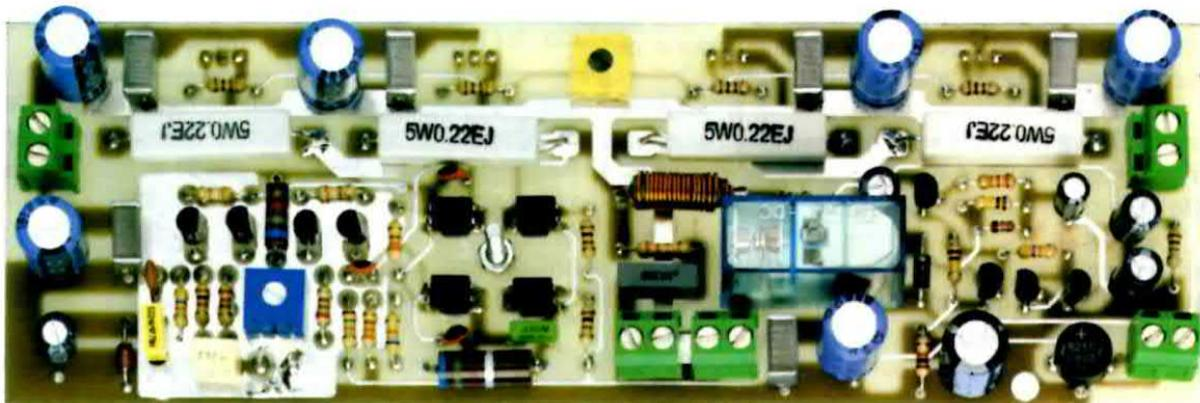
**Fig.6** Foto del circuito stampato dell'amplificatore con sopra montati tutti i suoi componenti ad esclusione dei quattro mosfet finali, che, come visibile nel disegno in fig.7, vanno prima montati sull'aletta e solo successivamente inseriti e saldati al circuito.
