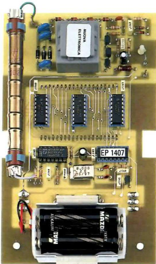
Fig.9 Ecco come si presenta il circuito stampato del contatore Geiger con sopra già montati tutti i componenti. Nella foto manca la serigrafia che risulta invece presente sugli stampati di produzione.
