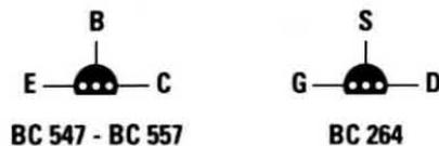
Fig.2 Connessioni dei transistor BC.547-BC.557 e del fet BC.264 viste da sotto. Le connessioni dei mosfet finali IRF.520 e IRF.9530 sono viste di fronte, mentre quelle dei mosfet di media potenza IRFD.110 e IRFD.9110 sono viste da sopra.
