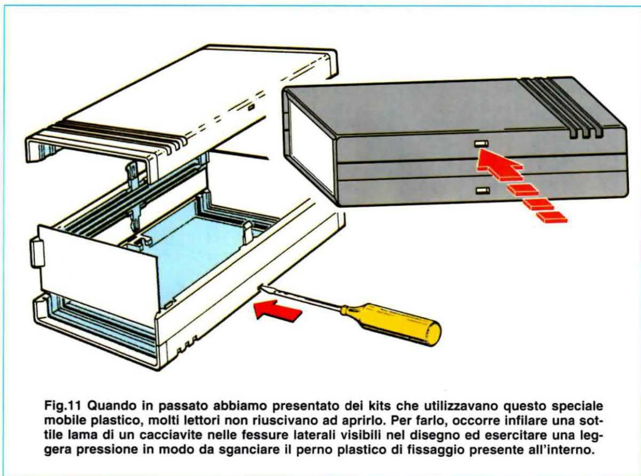
Fig.11 Quando in passato abbiamo presentato dei kits che utilizzavano questo speciale mobile plastico, molti lettori non riuscivano ad aprirlo. Per farlo, occorre infilare una sottile lama di un cacciavite nelle fessure laterali visibili nel disegno ed esercitare una leggera pressione in modo da sganciare il perno plastico di fissaggio presente all'interno.
