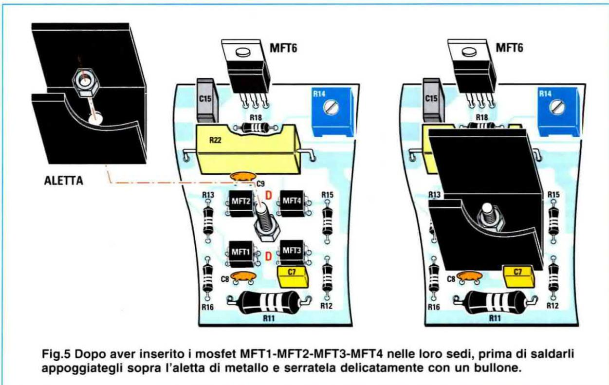
Fig.5 Dopo aver inserito i mosfet MFT1-MFT2-MFT3-MFT4 nelle loro sedi, prima di saldarli appoggiategli sopra l'aletta di metallo e serratela delicatamente con un bullone.
