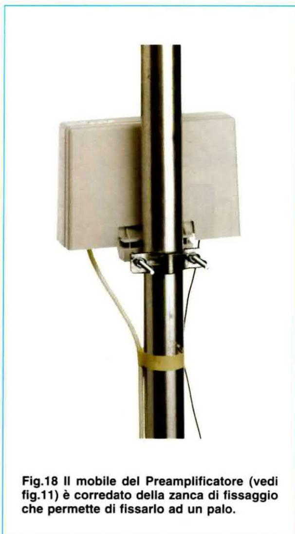
Fig.18 Il mobile del Preamplificatore (vedi fig.11) è corredato della zanca di fissaggio che permette di fissarlo ad un palo.
