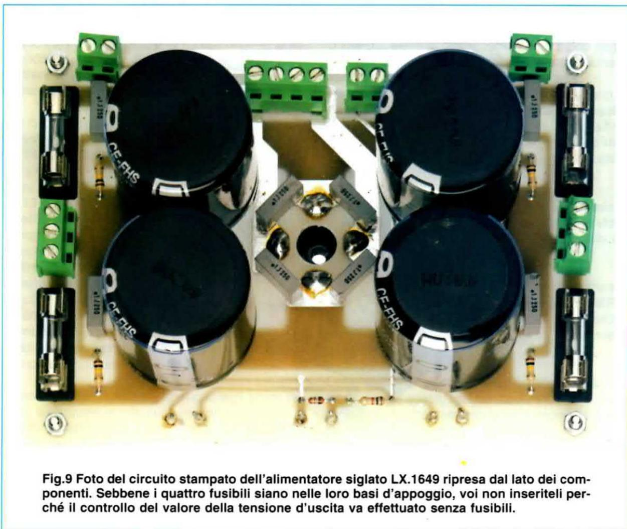
**Fig.9** Foto del circuito stampato dell'alimentatore siglato LX.1649 ripresa dal lato dei componenti. Sebbene i quattro fusibili siano nelle loro basi d'appoggio, voi non inseriteli perché il controllo del valore della tensione d'uscita va effettuato senza fusibili.
