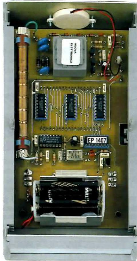
Fig.10 Lo stesso circuito già alloggiato nel mobile plastico. Sul pannello superiore di alluminio praticate un foro da 5 mm. per far uscire il suono prodotto dalla cicalina CP1 fissata al suo interno.
