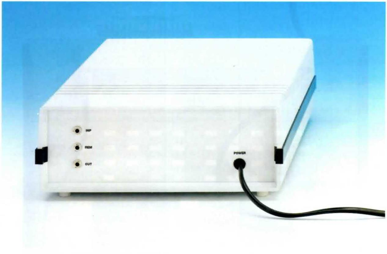
Fig.24 Nella foto è visibile il pannello posteriore del generatore sul quale si possono notare i connettori contrassegnati dalla dicitura INP, REM, OUT che consentono di collegare tra loro i generatori in cascata. Al connettore REM va collegato il pulsante Remote, che consente di interrompere in qualsiasi momento la sessione.
