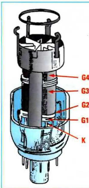
**Fig.12** Spaccato della struttura di un tubo sezionato verticalmente per metterne meglio in evidenza i componenti interni. I tubi a colori hanno un catodo per ogni colore R-G-B (vedi in fig.10 KR-KG-KB).
