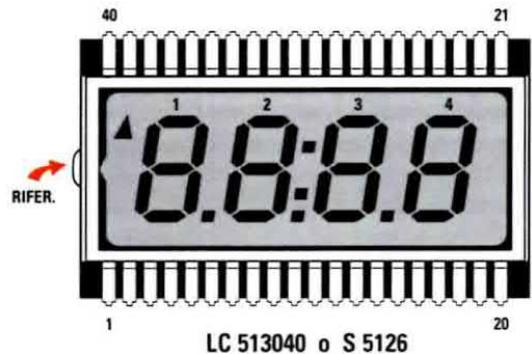
**Fig.4** Quando inserite il display nei due connettori, controllate che la **piccolissima protuberanza in vetro** (vedi Rifer.) risulti rivolta verso sinistra. Come riferimento può essere presente anche un segno **<** sulla cornice interna del display (vedi fig.6).
