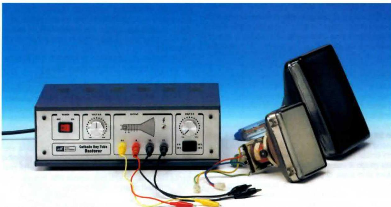
A mano a mano che il tubo a raggi catodici del televisore invecchia, perde di luminosità. L'apparecchio che vi proponiamo è in grado di rigenerare il tubo restituendogli pressoché tutte le proprietà che aveva all'origine.
