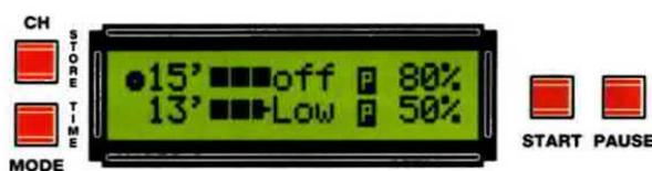
**Nota:** il controllo di presenza del trasduttore viene effettuato unicamente all'**accensione** dello strumento. Questo controllo può essere utile anche per accertarsi del **corretto funzionamento** dei trasduttori e del generatore ad ultrasuoni. Se anche dopo avere collegato i trasduttori al generatore vedete infatti apparire sul display la scritta **OFF**, significa che il trasduttore non funziona correttamente, oppure che c'è un problema sullo stadio finale di potenza del generatore.
