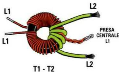
Fig.4 Sui due nuclei toroidali dei trasformatori T1 e T2 che vi vengono forniti con la bobina L1 già avvolta e completa della sua presa centrale, dovreste solo avvolgere le 4 spire per la bobina L2, utilizzando del sottile filo in rame flessibile isolato in plastica.
