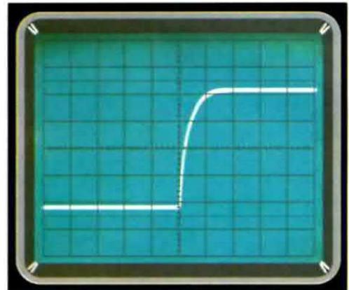
Fig.11 Se ora premete il tasto B del selettore Delay Mode e ruotate leggermente la manopola del potenziometro multigiri riuscirete a centrare sullo schermo il fronte di salita relativo al secondo picco, che risulterà così espanso di 100 volte.
