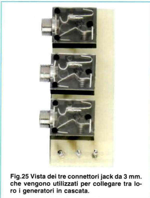
Fig.25 Vista dei tre connettori jack da 3 mm. che vengono utilizzati per collegare tra loro i generatori in cascata.
