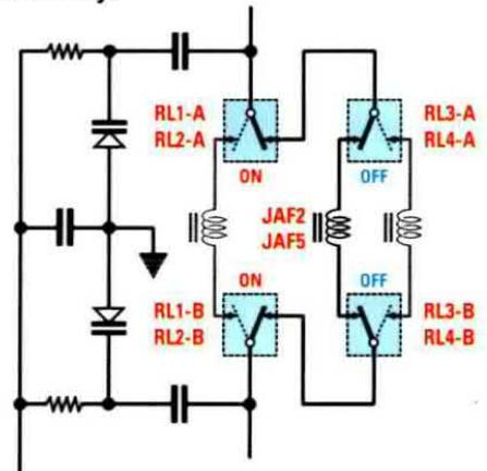
**Fig.6** Quando i relè **RL1** e **RL2** sono eccitati e i relè **RL3** e **RL4** sono diseccitati, sia sull'ingresso che sull'uscita dei due Mosfet risultano collegate le impedenze di sintonia **JAF2** e **JAF5** da **2,2 microhenry**.
