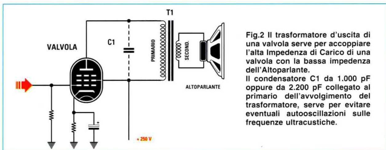
**Fig.2** Il trasformatore d'uscita di una valvola serve per accoppiare l'alta Impedenza di Carico di una valvola con la bassa impedenza dell'Altoparlante. Il condensatore C1 da 1.000 pF oppure da 2.200 pF collegato al primario dell'avvolgimento del trasformatore, serve per evitare eventuali autooscillazioni sulle frequenze ultracustiche.
