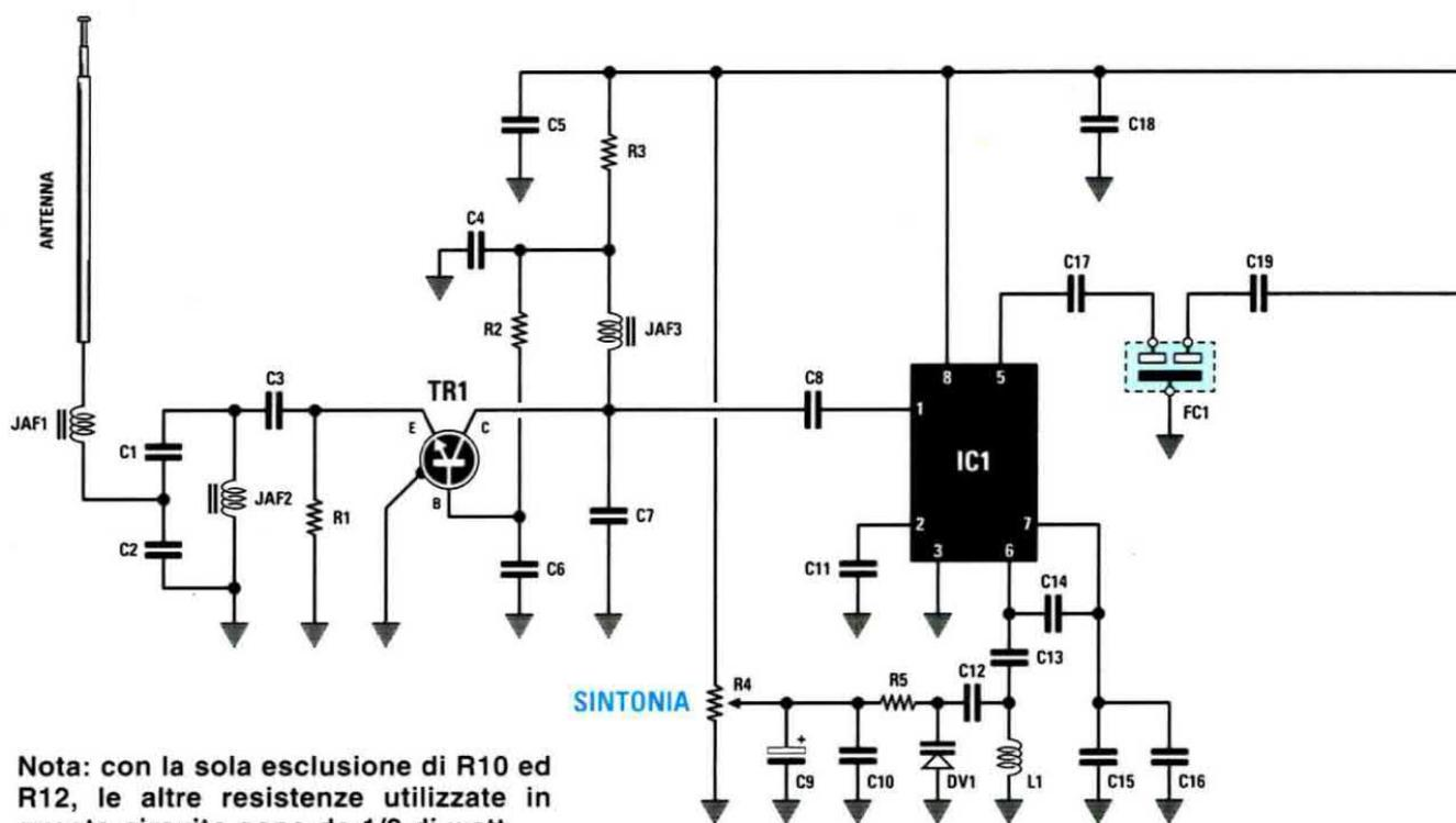
Se la tensione di alimentazione supera i **5 volt** l'integrato può seriamente danneggiarsi.
