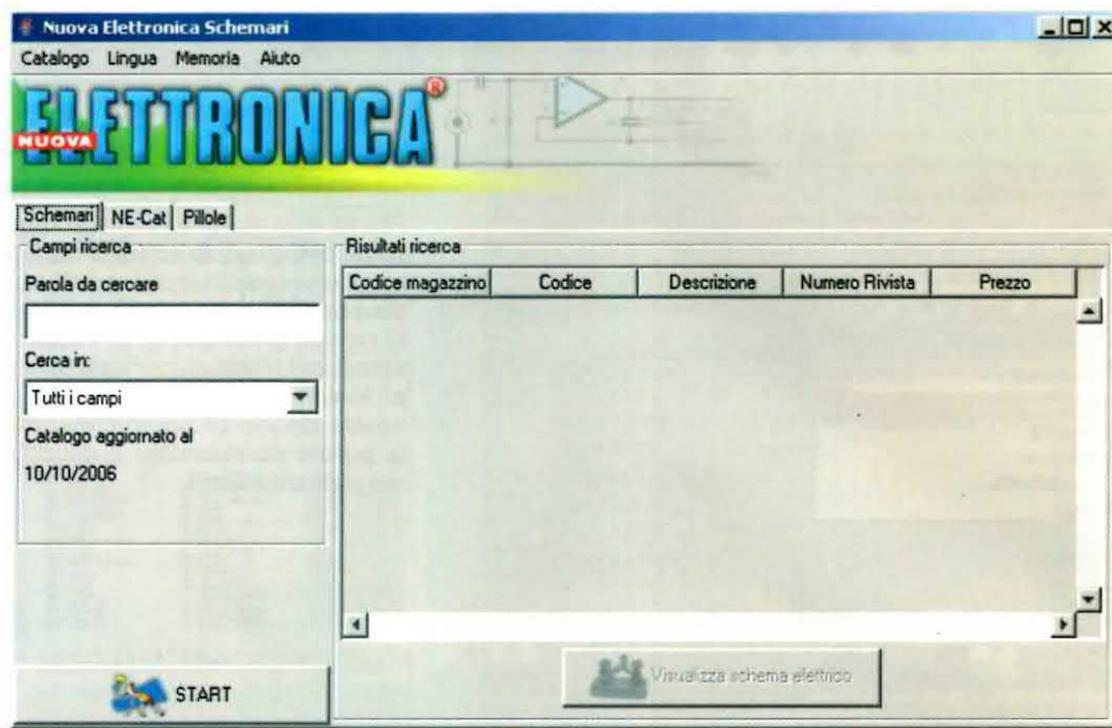
Fig.11 La finestra principale del programma Nuova Elettronica Schemari. In alto c'è la barra dei menu, a sinistra le schede Schemari, NE-Cat e Pillole per impostare le ricerche, mentre sulla destra la finestra che mostrerà i risultati delle vostre ricerche.
