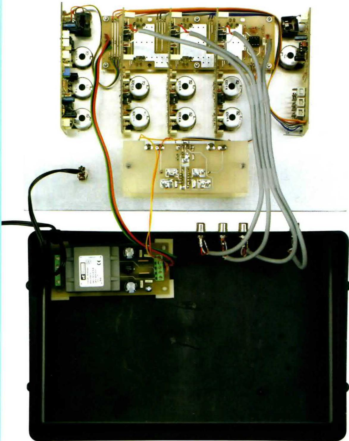
**Fig.28** Questa foto, insieme ai disegni precedenti di figg.26-27, vi aiuterà a portare a termine con successo la fase del cablaggio tra le diverse schede di cui si compone questo progetto. Come potete notare, tutti gli stampati sono fissati sul lato interno della mascherina del mobile, eccezion fatta per quello dell'alimentatore LX.1669 che va fissato per mezzo di quattro clips adesive direttamente sulla base del mobile.
