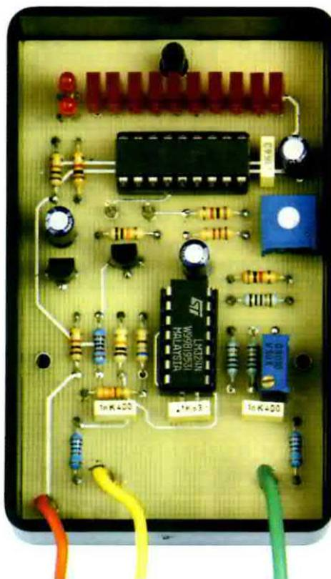
Fig.12 Foto dell'amperometro alloggiato nel mobile. I fili a cui sono collegati i coccodrilli (vedi fig.1) vanno saldati al circuito dopo averli fatti passare dai fori presenti sulla mascherina frontale.
