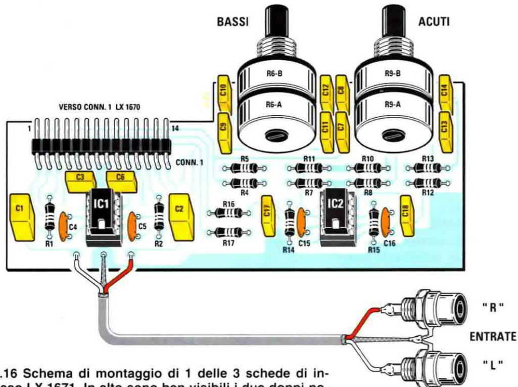
Fig.16 Schema di montaggio di 1 delle 3 schede di ingresso LX.1671. In alto sono ben visibili i due doppi potenziometri R6-A/R6-B e R9-A/R9-B rispettivamente per il controllo dei BASSI e degli ACUTI. In basso è visibile il collegamento alle due prese BF relative agli ingressi "L" ed "R" del mixer.
