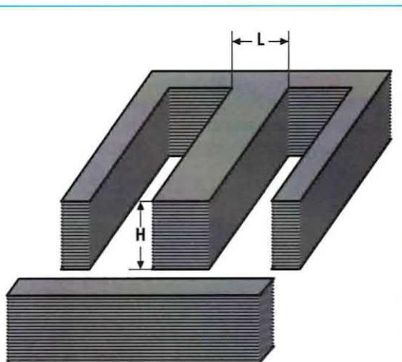
Fig.3 Per calcolare i centimetri quadrati del nucleo di un trasformatore d'uscita basta moltiplicare la larghezza (vedi L) della colonna centrale per l'altezza (vedi H). I lamierini vengono inseriti nel cartoccio in modo che le E si trovino da un lato e le I dal lato opposto.
