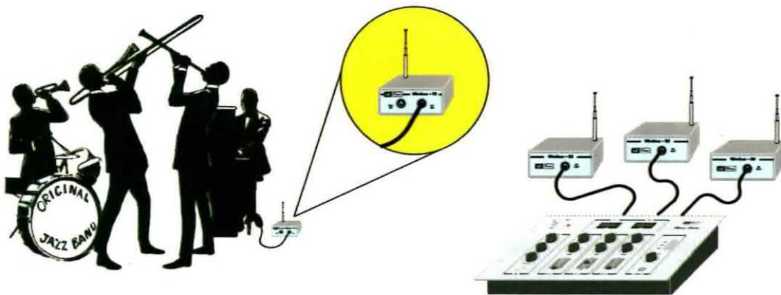
Fig.1 Collegando i canali di ingresso del mixer al nostro ricevitore LX.1491 e abbinando a ciascuno strumento musicale il corrispondente trasmettitore LX.1490 è possibile effettuare via radio il mixaggio di tutti i segnali audio, eliminando la necessità di fastidiosi cavi di collegamento.
