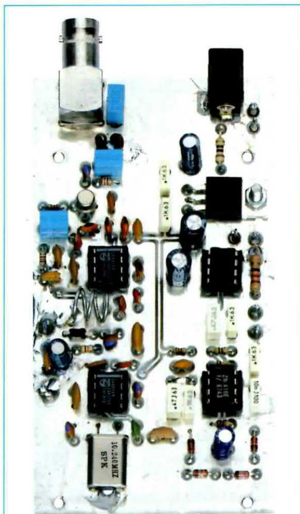
**Fig.9** Foto del circuito stampato LX.1662 con sopra già montati tutti i suoi componenti. Sulla destra potete osservare il disegno pratico di questo montaggio.
