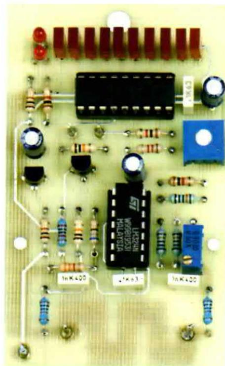
**Fig.4** Schema pratico di montaggio e foto dell'amperometro a diodi led prodotto in kit con la sigla LX.1675. Quando saldate i diodi led fate in modo che il loro corpo sia accostato alla mascherina serigrafata, perché appariranno ai vostri occhi più luminosi.
