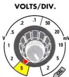
Fig.1 Se nel DDS Generator non utilizziamo nessun amplificatore RF, in uscita preleveremo un segnale RF di circa 3 volt picco/picco che scenderà a 1,5 volt picco/picco applicando un carico di 50-52 ohm.
