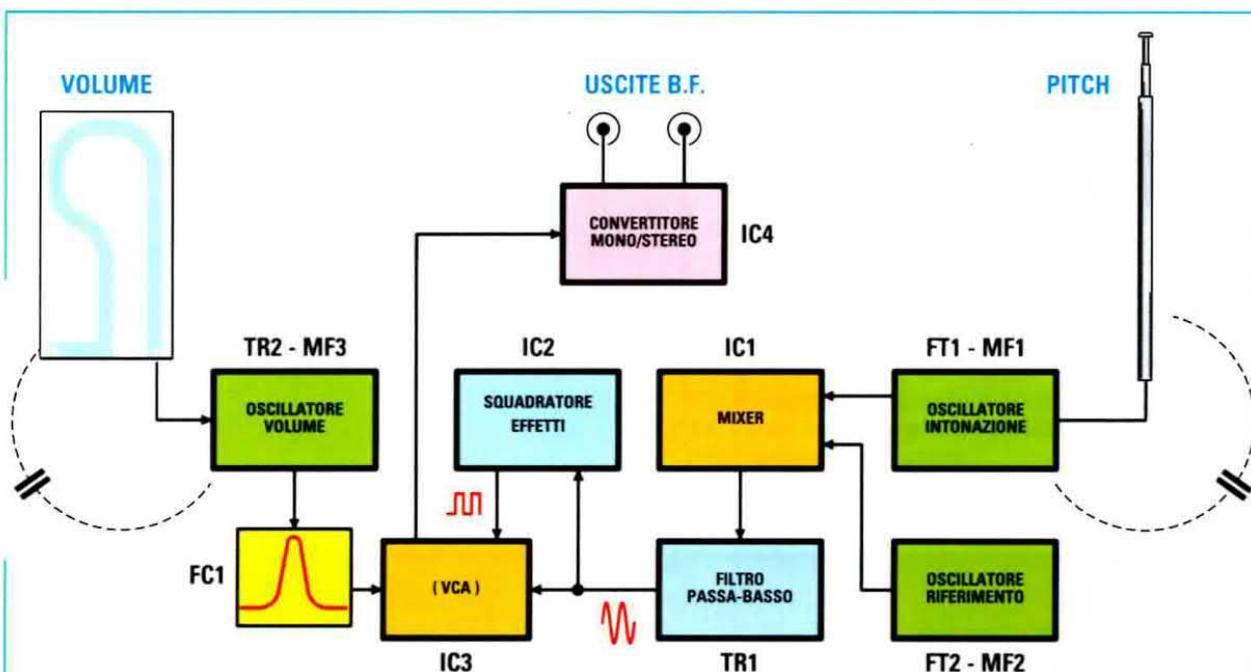
Fig.2 Schema a blocchi del Theremin che abbiamo progettato. Le mani, con la loro capacità parassita, influenzano il campo elettromagnetico che circonda le antenne. Muovendo la mano attorno all'antenna Pitch, otteniamo note più acute o più gravi. Muovendo la mano attorno all'antenna Volume, otteniamo suoni più o meno intensi.
