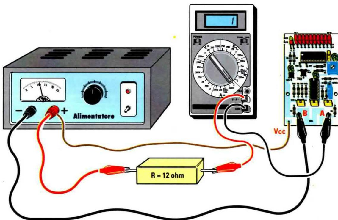
**Fig.5** Come abbiamo spiegato nell'articolo, in via teorica lo strumento può essere tarato avvalendosi dei test point TP1 e TP2 (vedi fig.3). Poiché però non si può prescindere dalle inevitabili tolleranze dei componenti, vi suggeriamo di effettuare una taratura "sul campo" utilizzando un tester per misure in corrente continua, un alimentatore ed un carico, che vanno collegati all'amperometro come esemplificato in questo disegno.
