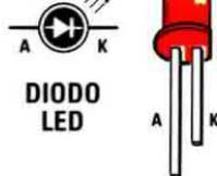
Fig.6 Qui a sinistra le connessioni E.M.U dello stabilizzatore IC2 e quelle del diodo led, il cui terminale più lungo, come saprete, è l'Anodo.
