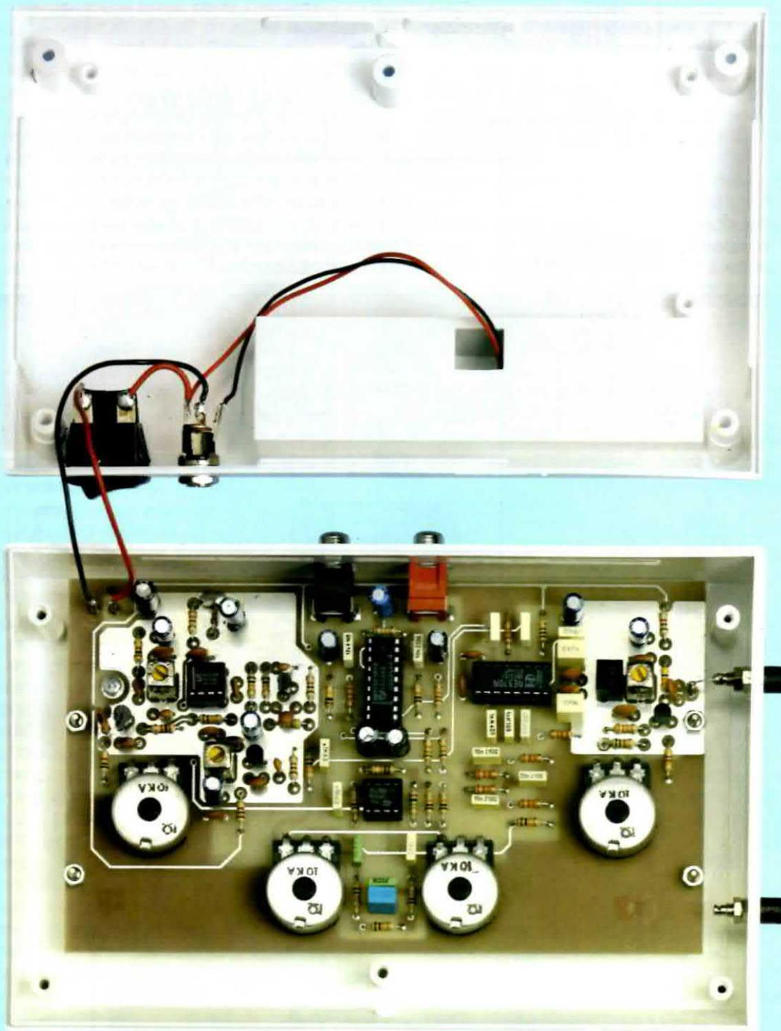
**Fig.16** Foto del circuito stampato collocato nel suo contenitore plastico. Prima di chiudere il mobile dovete tarare le tre medie frequenze secondo quanto descritto nella pagina a fianco. Vi ricordiamo che per ottenere una corretta taratura, lo strumento deve essere appoggiato lontano da eventuali masse metalliche.
