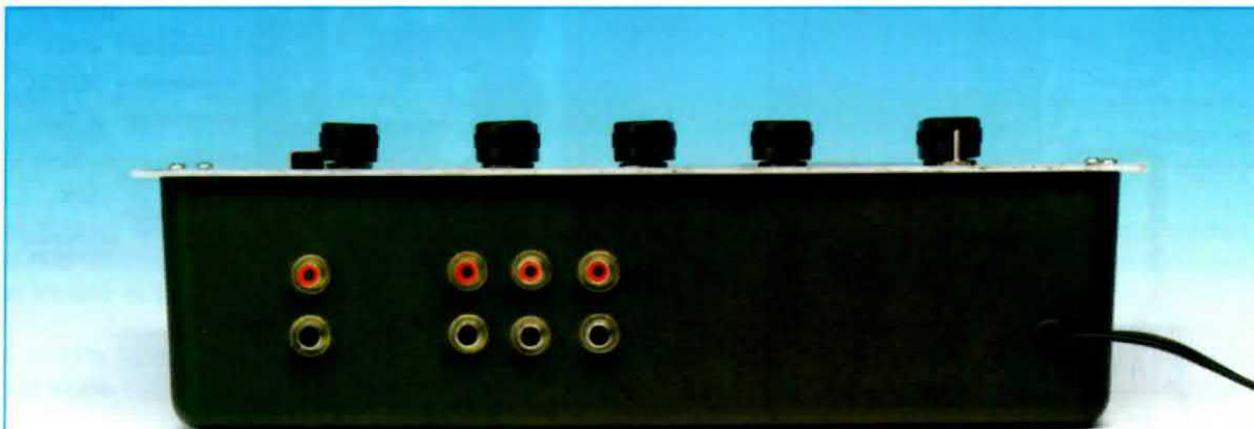
**Fig.12** In questa foto il mobile contenente le schede che compongono il nostro mixer è visto dal retro. A sinistra sono ben visibili le due prese BF relative ai due canali **L** e **R** di uscita del mixer e in posizione quasi centrale il gruppo delle tre coppie di prese BF corrispondenti agli ingressi stereo delle 3 schede **LX.1671**.
