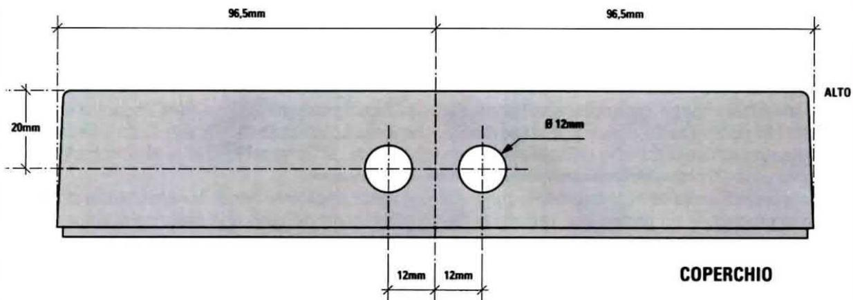
**Fig.11** Il mobile di plastica che abbiamo scelto per contenere il circuito stampato del Theremin viene fornito privo di fori. Per semplificare le operazioni di foratura, in questo disegno abbiamo riprodotto le quote dei fori circolari per le prese d'uscita di BF, da eseguirsi sul retro del coperchio con una punta da 12 mm.
