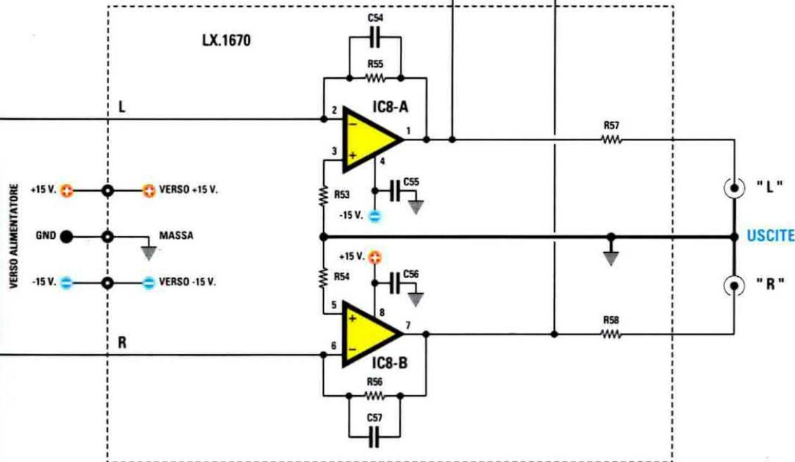
Fig.7 Schema elettrico completo del mixer.
