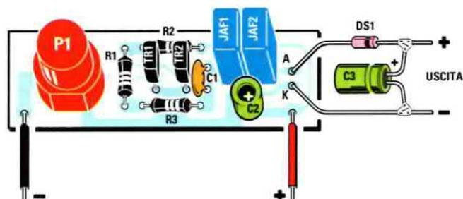
Fig.8 Disegno del montaggio del circuito riportato in fig.3. Il diodo DS1 va collegato al filo proveniente dal foro A, rivolgendolo il lato contornato da una fascia nera verso l'esterno, mentre il terminale positivo del condensatore elettrolitico C3 va collegato al diodo ed il terminale negativo al filo proveniente dal foro K.
