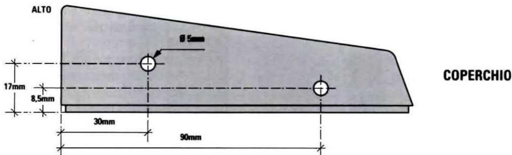
**Fig.12** Guardando il coperchio dal davanti, con la parte bassa appoggiata sul tavolo da lavoro, dovete eseguire sul fianco sinistro due piccoli fori circolari dello stesso diametro, ma ad altezze diverse. In questi fori andranno montate le due boccole miniatura, che non devono essere isolate perché il mobile è di plastica.
