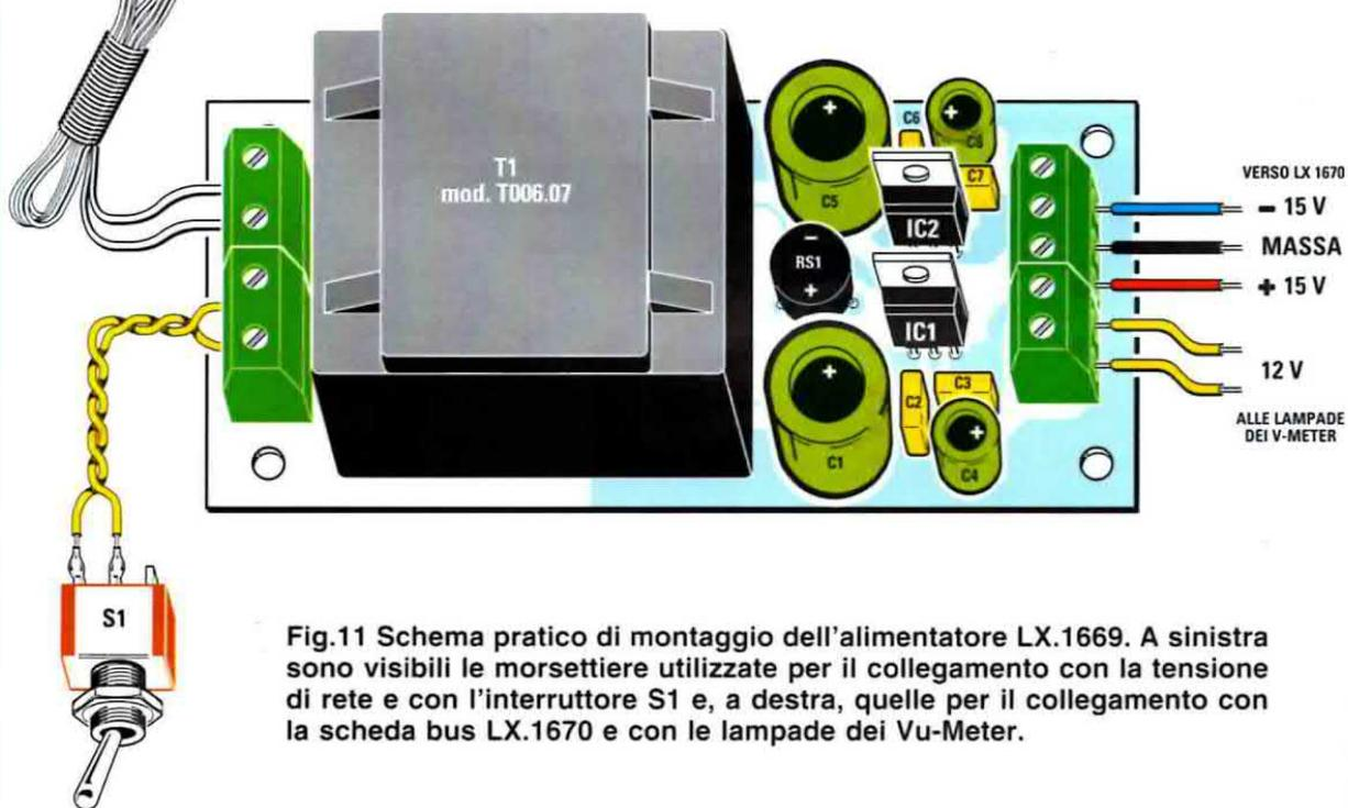
Fig.11 Schema pratico di montaggio dell'alimentatore LX.1669. A sinistra sono visibili le morsettiere utilizzate per il collegamento con la tensione di rete e con l'interruttore S1 e, a destra, quelle per il collegamento con la scheda bus LX.1670 e con le lampade dei Vu-Meter.
