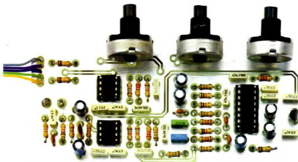
Fig.22 In questa foto è riprodotta la scheda eco e ingresso microfono che andrà collocata in senso perpendicolare al retro della mascherina del mobile (vedi fig.27 a destra).
