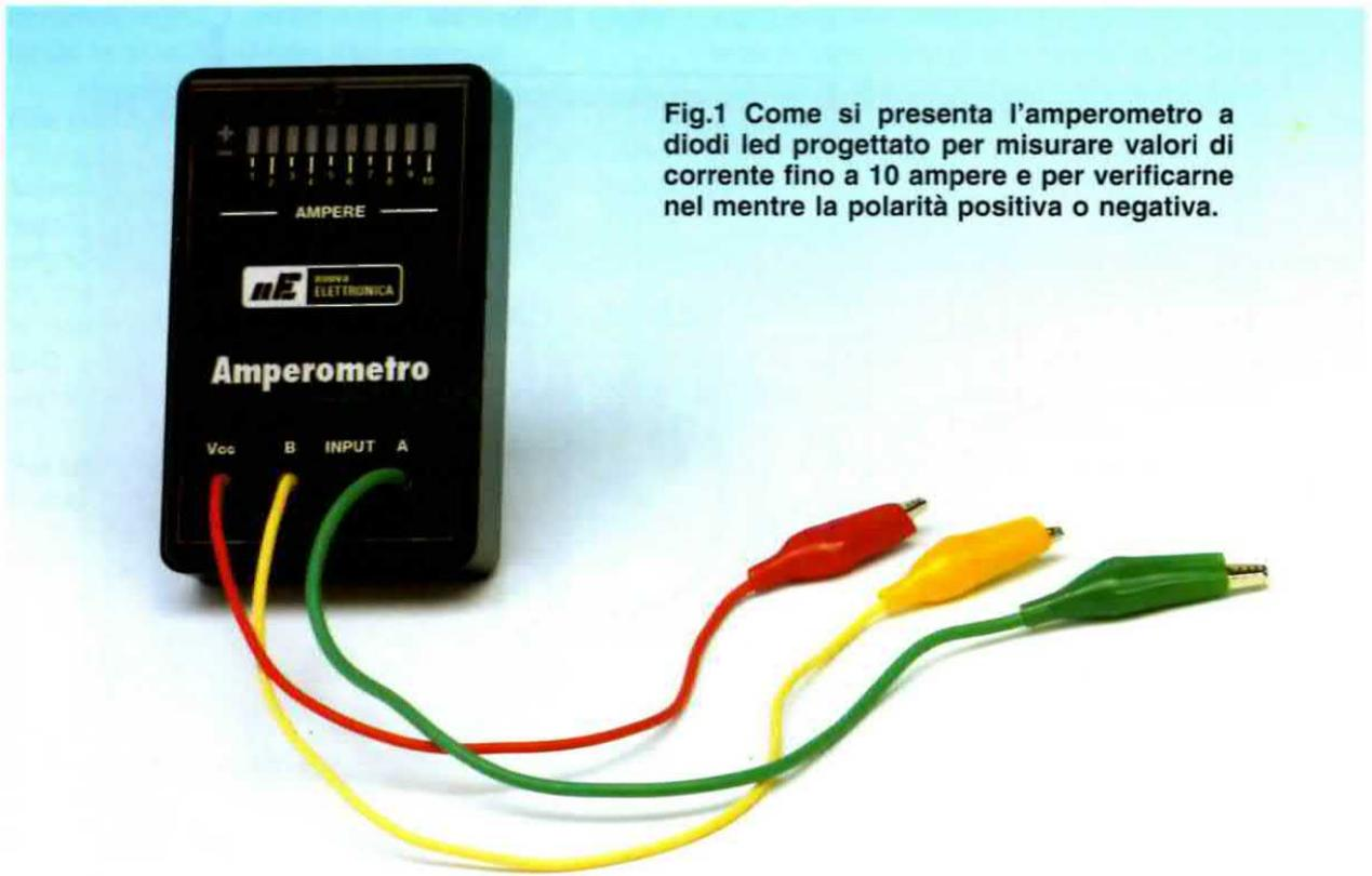
Fig.1 Come si presenta l'amperometro a diodi led progettato per misurare valori di corrente fino a 10 ampere e per verificarne nel mentre la polarità positiva o negativa.
