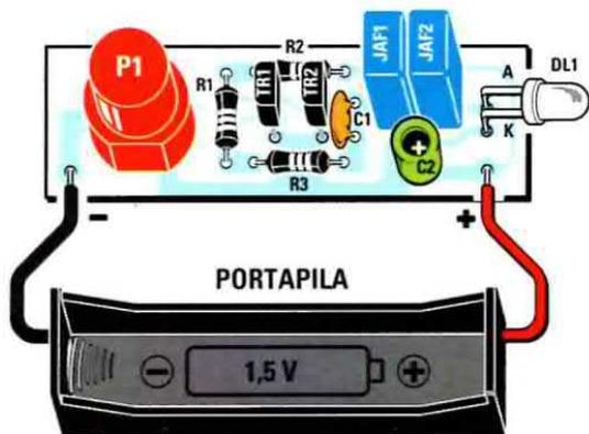
Fig.5 Schema pratico di montaggio della pila siglata LX.1664. I transistor ZTX.653 vanno saldati al circuito rivolgendolo la parte piatta del loro corpo verso destra.
