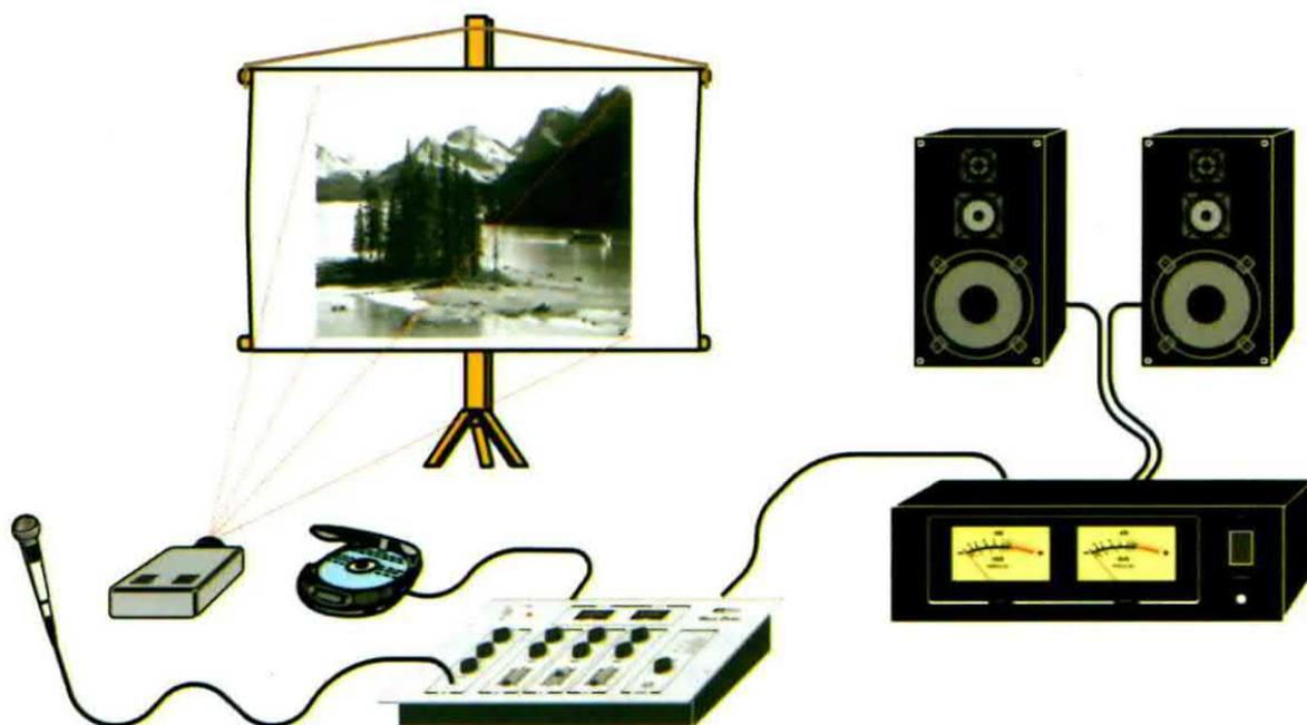
**Fig.2** Collegando un microfono all'ingresso MIC del mixer, un lettore di CD-Rom ad uno degli ingressi e l'uscita del mixer al vostro impianto stereo potrete allietare le proiezioni di filmati e diapositive, sovrapponendo il commento parlato ad un piacevole sottofondo musicale.
