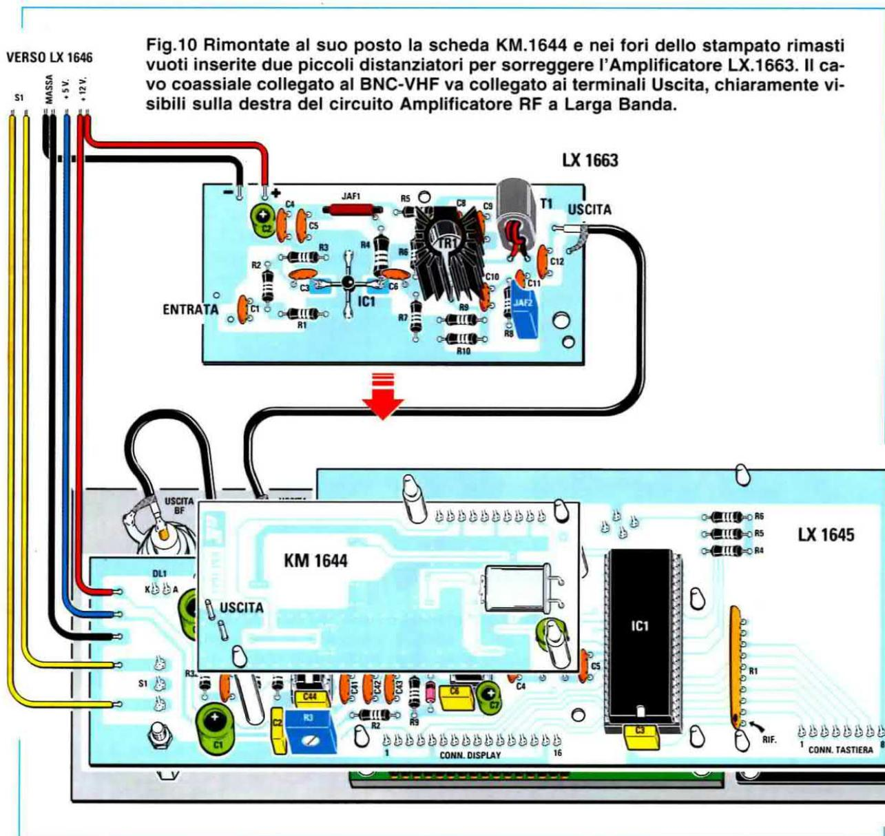
L'estremità **D** si collega ai **12 volt** di alimentazione, mentre l'estremità **A** alla pista che va al Collettore di **TR1**.
