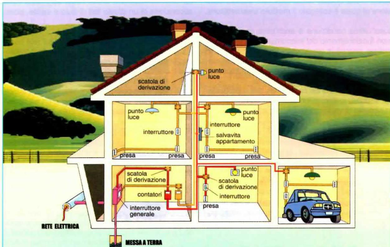
**Fig.1** Grazie al telecomando ad onde convogliate è possibile attivare uno o più dispositivi in qualunque punto della propria abitazione, utilizzando per la trasmissione del segnale la rete di alimentazione esistente a 230 Volt.
