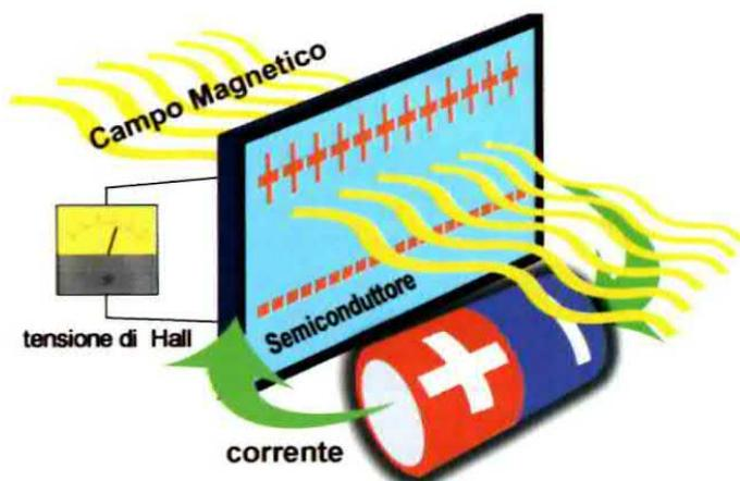
Si chiama **elemento di Hall** la sottile striscia di materiale semiconduttore in cui viene fatta scorrere la corrente fornita da un generatore. Immergendo l'elemento semiconduttore in un campo magnetico, Hall notò che la forza del campo magnetico agiva sulle cariche in conduzione, generando una differenza di potenziale, detta **tensione di Hall**, sulle facce opposte dell'elemento.
