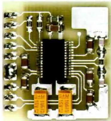
Fig.18 Foto ingrandita dell'integrato siglato PCM2902 montato sul piccolo circuito stampato siglato KM1667, che forniamo già montato in SMD.
