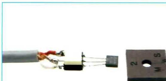
Fig.13 Foto del sensore ad effetto di Hall e del magnete da 190 gauss. Nel corso della taratura spostate il magnete fino ad avere la massima lettura. Le superfici magnete/sensore devono sempre toccarsi.
