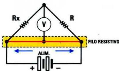
Fig.20 Il ponte a filo è un circuito semplificato del ponte di Wheatstone. Permette di misurare in modo preciso il valore della resistenza RX, conoscendo la lunghezza di un filo resistivo metallico lungo il quale scorre un cursore collegato al ramo in cui è inserito un galvanometro.
