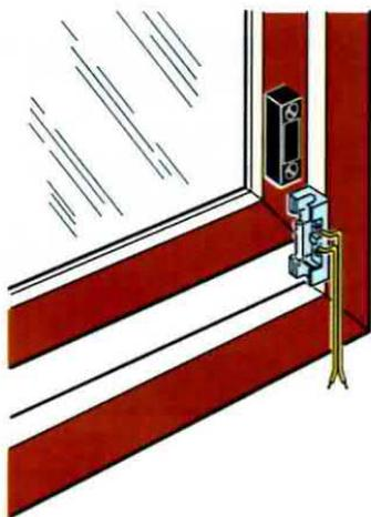
**Fig.4** Oltre ai sensori ad infrarossi potrete collocare sul battente di porte e finestre dei sensori magnetici. Questi dispositivi sono composti da due blocchetti a forma di parallelepipedo, in uno dei quali è presente un contatto che si chiude quando viene accostato l'altro parallelepipedo, contenente un piccolo magnete.
