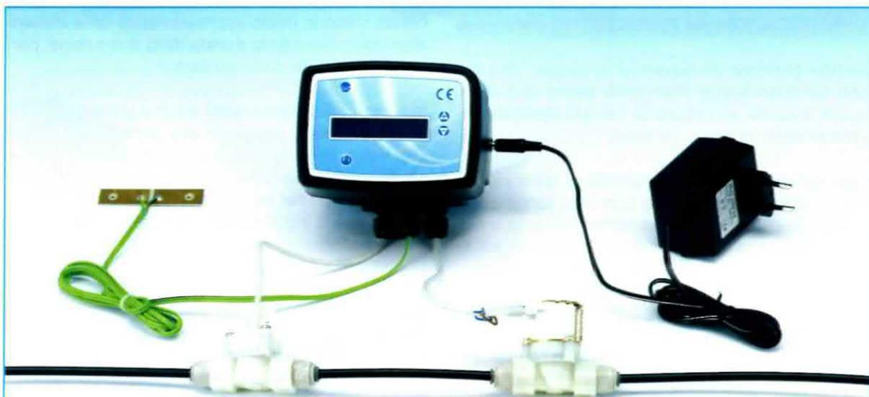
**Fig.1** Collegando il nostro flussimetro al sensore contaltri e ad una elettrovalvola di mandata è possibile effettuare erogazioni molto precise sia di acqua che di qualsiasi altro tipo di liquido. Sul display viene visualizzato il volume erogato in litri, la portata in litri al minuto ed il numero di cicli di erogazione eseguiti. Il flussimetro viene fornito in contenitore impermeabile, con classe di protezione IP42 e completo della certificazione CE.
