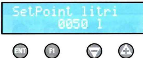
Questo significa che, dopo avere erogato il volume di **50 litri**, il flussimetro bloccherà la **pompa** e l'**elettrovalvola**, fermando l'erogazione.
