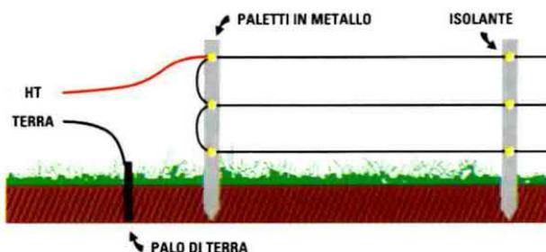
**Fig.2** Se i paletti del vostro recinto sono di metallo, dovrete isolarli dal filo utilizzando degli isolatori in ceramica. Conviene inoltre racchiudere la bobina per auto all'interno di un contenitore plastico che fisserete vicino ai paletti della recinzione.
