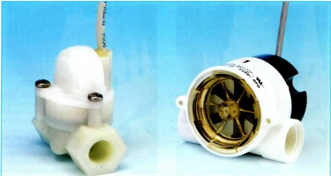
**Fig.16** Il flussimetro è predisposto per essere collegato al sensore contaltri da noi fornito, raffigurato a sinistra in figura, con portata da 0 a 7 litri/minuto, ma può essere collegato anche ad altri contaltri esistenti in commercio, con portata e risoluzione diversa. In questo caso è sufficiente eseguire la procedura di calibrazione indicata più avanti nel relativo paragrafo.
