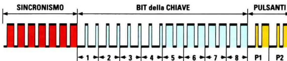
Fig.4 Dall'integrato HT6014 utilizzato nello stadio trasmittente come Encoder escono 27 impulsi: di questi, i primi sette di colore rosso servono per il Sincronismo, gli altri 16 di colore celeste per il Codice Chiave, mentre gli ultimi 4 impulsi di colore giallo servono per far riconoscere al Decoder quali dei pulsanti P1-P2 è stato premuto.
