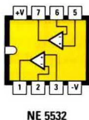
Fig.2 Connessioni viste da sopra del doppio operativo siglato NE.5532. Abbiamo usato questo integrato perché ha un basso rumore ed una bassa impedenza d'uscita.
