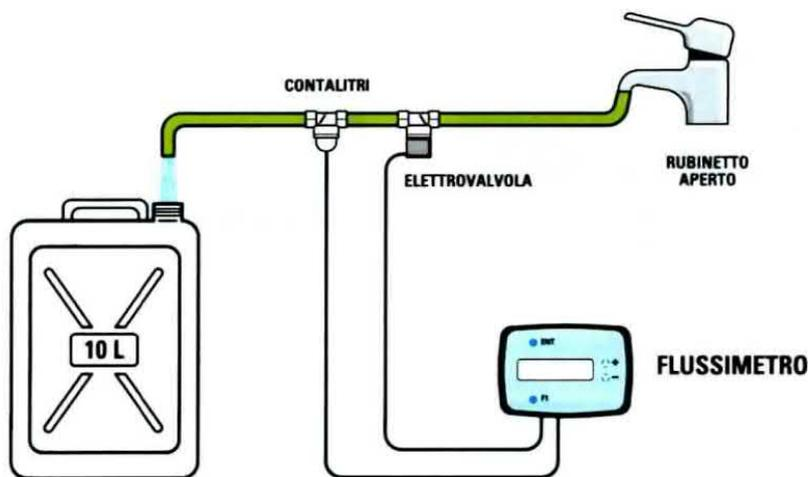
**Fig.19** Se utilizzate un tipo di contalitri diverso da quello da noi fornito, dovrete eseguire la procedura di calibrazione, utilizzando un recipiente di volume noto. Questa procedura può essere rieseguita anche dopo un lungo periodo di utilizzo per ricalibrare il contalitri.
