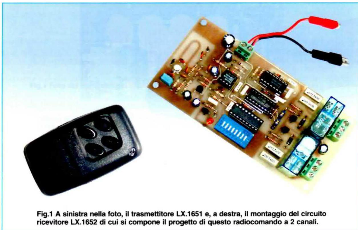
Fig.1 A sinistra nella foto, il trasmettitore LX.1651 e, a destra, il montaggio del circuito ricevitore LX.1652 di cui si compone il progetto di questo radiocomando a 2 canali.
