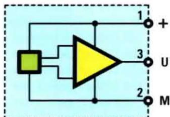
Fig.1 Connessioni viste di fronte e schema a blocchi interno del sensore di campo magnetico ad effetto di Hall siglato UGN.3503U. Questo sensore è sensibile da entrambi i lati ed è in grado di rilevare la presenza di un campo magnetico e determinarne la polarità negativa o positiva.
