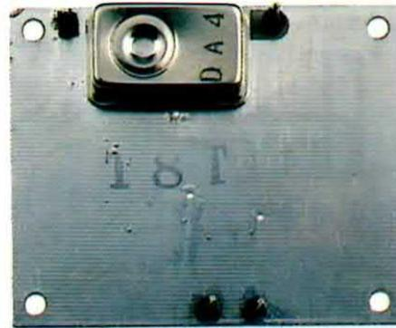
Fig.3 Come potete notare, sul retro del circuito stampato trova posto il minuscolo modulo DRO, cioè lo stadio oscillatore utilizzato per generare la frequenza dei 10 GHz.
