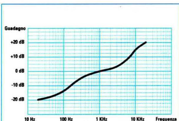
**Fig.5** Lo standard RIAA prevede che durante la fase registrazione di un disco in vinile il segnale da incidere all'interno del microsolco venga attenuato nelle frequenze più basse ed amplificato nelle frequenze più alte.
