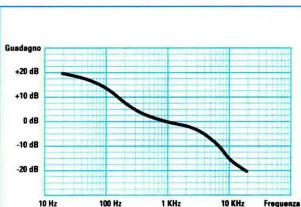
**Fig.6** In fase di riproduzione del disco il segnale proveniente dal pick-up del giradischi viene inviato al circuito di equalizzazione RIAA che provvede a normalizzarlo amplificando le frequenze basse ed attenuando le frequenze alte.
