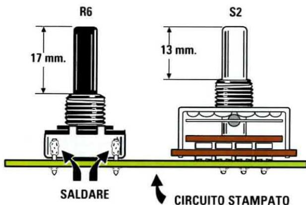
Fig.5 Prima di saldare il potenziometro ed il commutatore accorciate i loro perni con un piccolo seghetto. Per far sì che il potenziometro non si muova, oltre a saldare i suoi terminali (vedi fig.4), saldate al suo corpo due spezzoni di filo di rame come indicato nel disegno.
