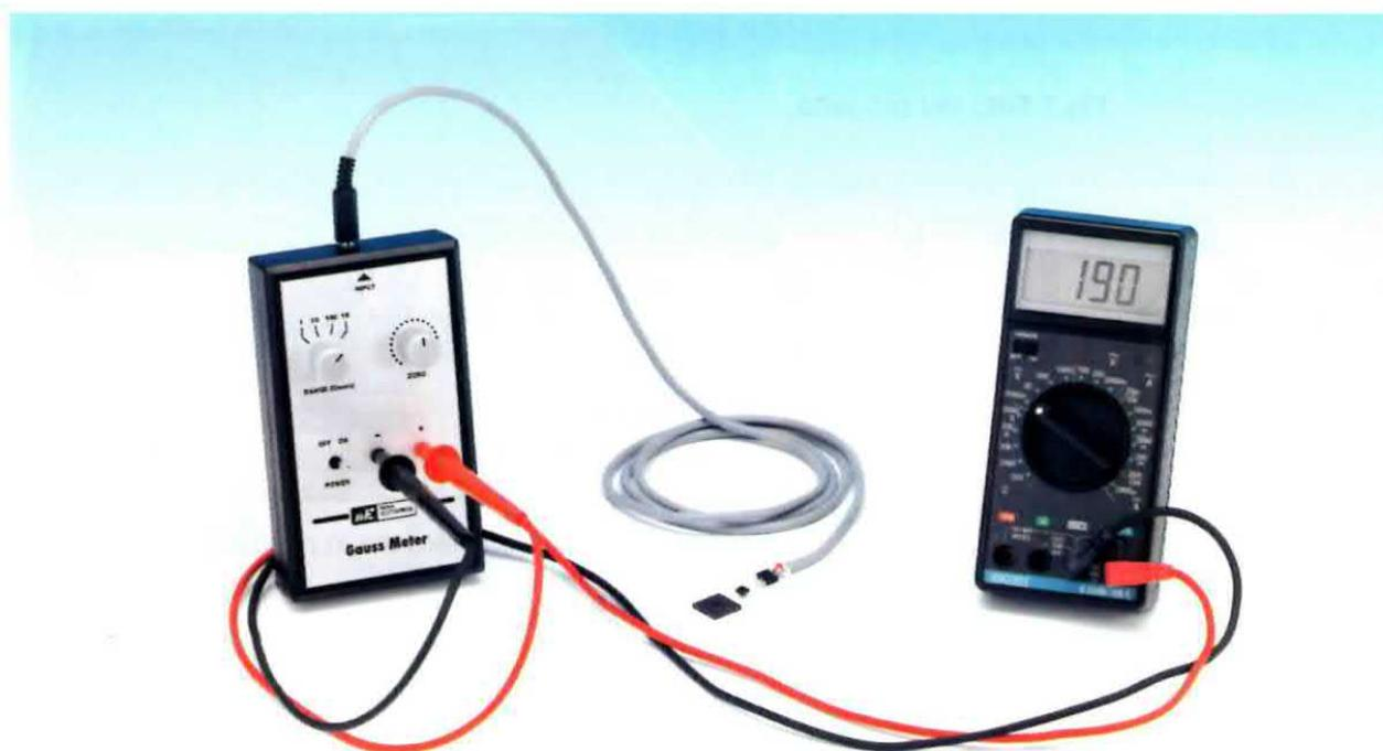
Avvalendosi per la visualizzazione di un comune tester, meglio se digitale, potete costruire un economico gaussmetro per determinare la forza del campo magnetico generato da qualsiasi bobina percorsa da corrente.
