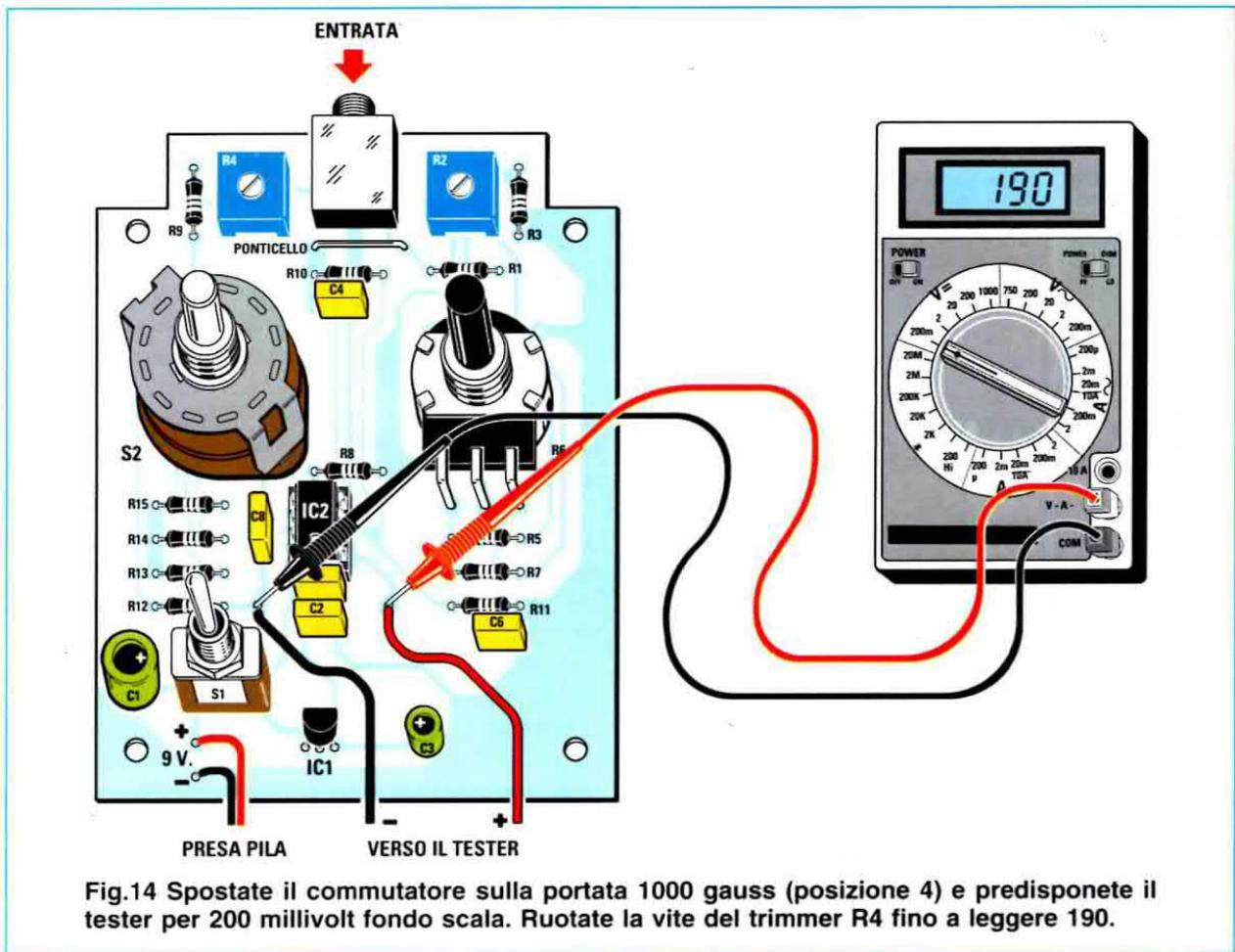
Fig.14 Spostate il commutatore sulla portata 1000 gauss (posizione 4) e predisponete il tester per 200 millivolt fondo scala. Ruotate la vite del trimmer R4 fino a leggere 190.
