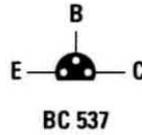
Fig.2 Connessioni viste da sopra dell'integrato operativo TL.081, che si può sostituire con l'integrato LF.353. Le connessioni del transistor BC.537 sono invece viste da sotto.
