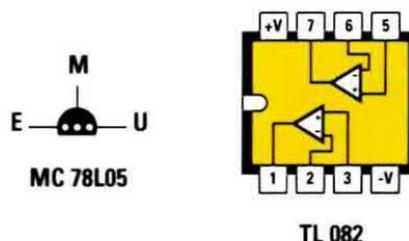
**Fig.3** Connessioni dello stabilizzatore di tensione **MC.78L05** viste da sotto e del doppio operativo **TL.082** viste da sopra. Nello schema elettrico visibile a fianco, sul piedino **1** dell'integrato **TL.082** si ha una tensione costante di **2,5 volt**, e sul piedino **7** una tensione che varia di **+/- 1,3 millivolt** circa per ogni **gauss** rilevato.
