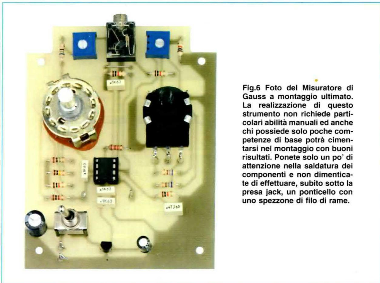
**Fig.6** Foto del Misuratore di Gauss a montaggio ultimato. La realizzazione di questo strumento non richiede particolari abilità manuali ed anche chi possiede solo poche competenze di base potrà cimentarsi nel montaggio con buoni risultati. Ponete solo un po' di attenzione nella saldatura dei componenti e non dimenticate di effettuare, subito sotto la presa jack, un ponticello con uno spezzone di filo di rame.
