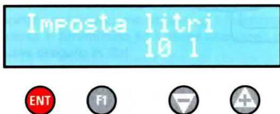
Se avete a disposizione un contenitore calibrato da **5 litri**, dovete modificare il volume impostato premendo ripetutamente il tasto - fino ad ottenere sul display il valore desiderato.
