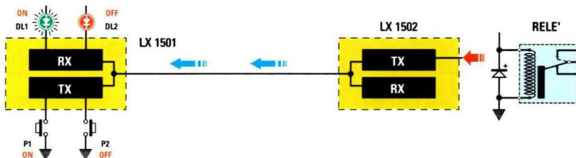
Fig.6 Non appena il relè si eccita, lo stadio trasmettente presente nel ricevitore siglato LX.1502 invia di ritorno, sempre sulla linea dei 230 Volt, degli impulsi codificati che, captati dallo stadio RX del trasmettitore siglato LX.1501, provvedono a far accendere il diodo led DL1-ON.
