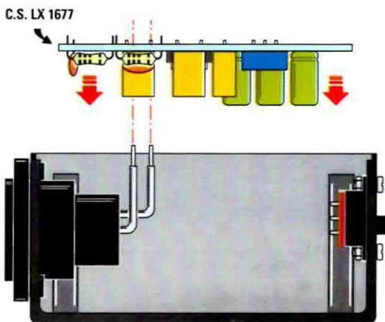
**Fig.6** Infilate nel contenitore lo stampo, sul quale dovete aver già saldato i fili per i collegamenti all'interruttore, alla pila e alla presa uscita, con i componenti rivolti verso il basso in modo che i terminali della presa microfono entrino nei fori.
