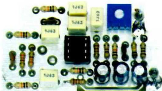
Fig.4 Nel montaggio dei componenti sul circuito stampato non incontrerete difficoltà; fate solo attenzione ad inserire l'integrato in modo che la fessura sul suo corpo sia rivolta verso l'alto.
