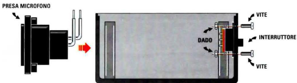
**Fig.5** Per prima cosa bloccate con due bulloni su un lato del contenitore l'interruttore di accensione, che si incastra perfettamente nella fessura predisposta. Sul lato opposto infilate fino in fondo la presa microfono con i terminali rivolti verso l'alto. Anche questa presa entra in maniera precisa nella sua fessura.
