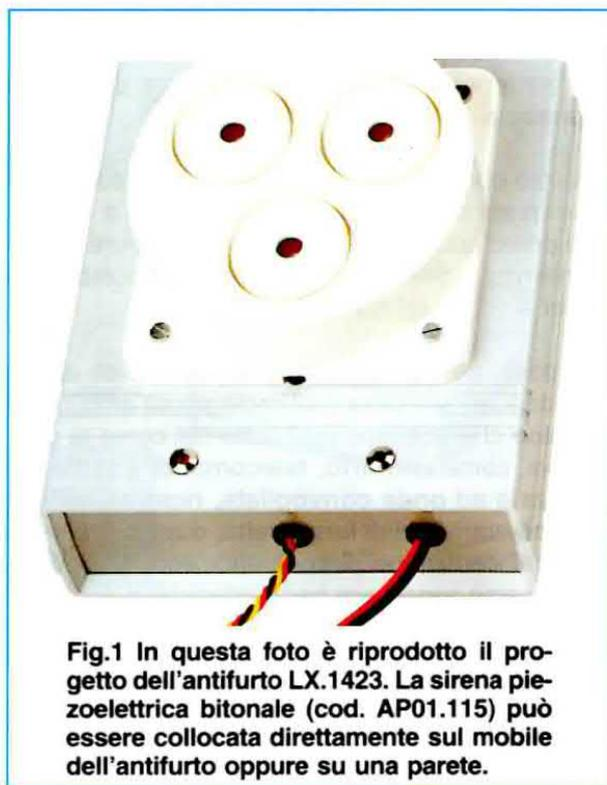
Fig.1 In questa foto è riprodotto il progetto dell'antifurto LX.1423. La sirena piezoelettrica bitonale (cod. AP01.115) può essere collocata direttamente sul mobile dell'antifurto oppure su una parete.
