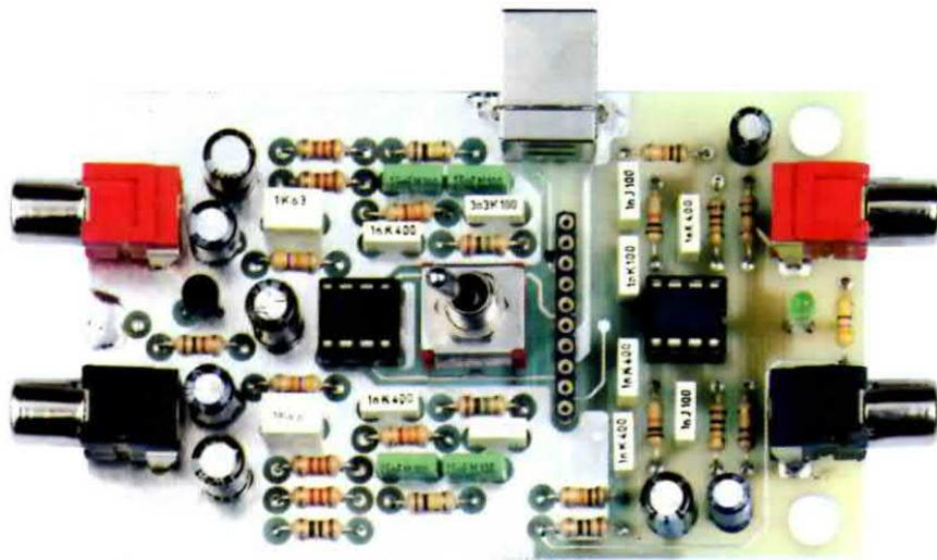
**Fig.21** In questa foto è riprodotto lo schema pratico di montaggio del convertitore audio LX.1666. In alto è ben visibile il connettore CONN.1 per la presa USB, sul lato sinistro le prese di ingresso e sul lato destro le prese di uscita del segnale siglate "R" e "L".
