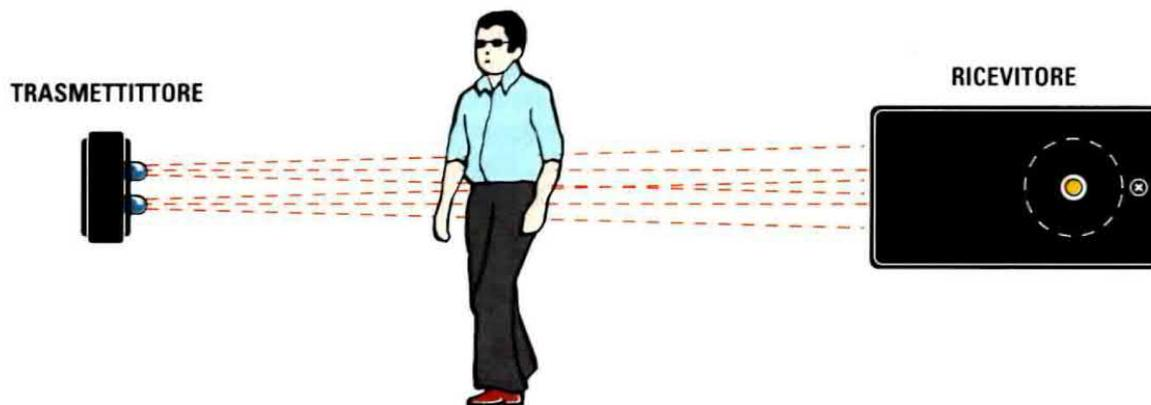
**Fig.1** Nel collocare il trasmettitore e il ricevitore di cui si compone questo progetto in un passaggio obbligato che desiderate tenere sotto controllo, dovrete fare in modo che il fascio di raggi infrarossi emesso dai diodi emittenti del trasmettitore colpisca direttamente la superficie sensibile del diodo presente nel ricevitore. La portata massima che questo dispositivo riesce a coprire è di 7 metri circa.
