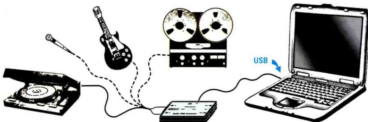
**Fig.2** Il convertitore audio stereo USB trasforma il segnale audio analogico proveniente da una sorgente sonora in un segnale digitale, che può essere trasferito ad un computer tramite la presa USB e memorizzato sull'hard disk.
