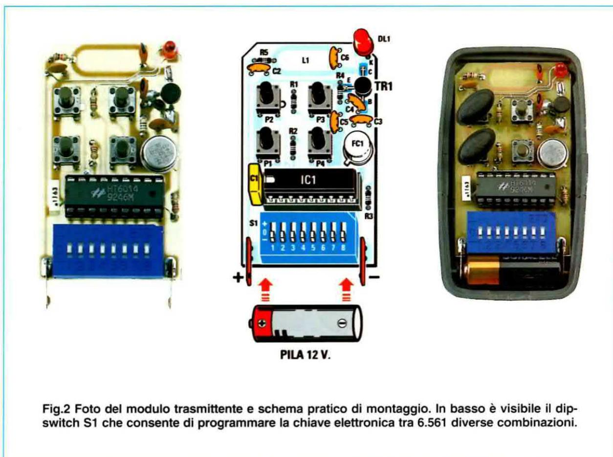
Fig.2 Foto del modulo trasmettente e schema pratico di montaggio. In basso è visibile il dip-switch S1 che consente di programmare la chiave elettronica tra 6.561 diverse combinazioni.
