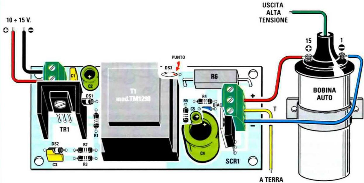
Fig.3 Schema pratico del generatore di scariche elettriche. A destra è visibile la morsetteria a 3 poli per il collegamento alla bobina ad alta tensione e alla terra. Precisiamo che la bobina non viene da noi fornita, ma che potrete utilizzare per generare l'alta tensione qualunque bobina da automobile.
