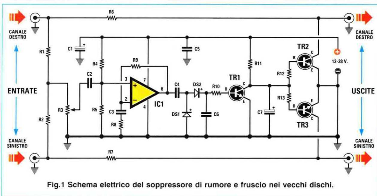
Fig.1 Schema elettrico del soppressore di rumore e fruscio nei vecchi dischi.
