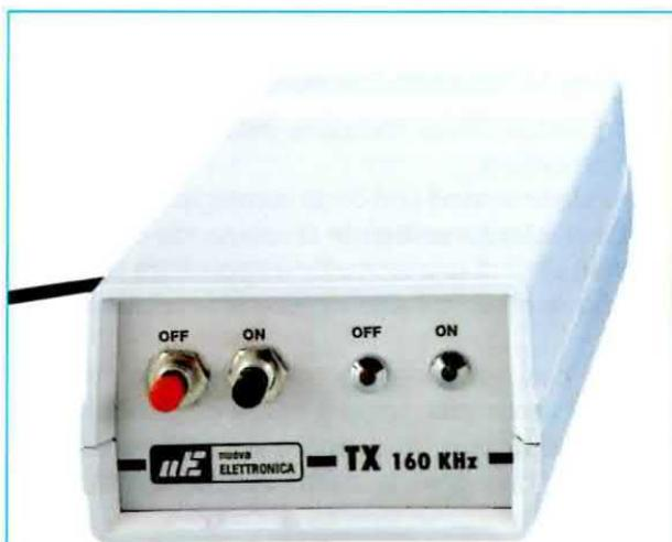
Fig.2 Foto del mobile che racchiude lo stadio trasmittente siglato LX.1501. Come potete notare, nel pannello frontale sono inseriti i due pulsanti ON e OFF e i diodi di controllo.
