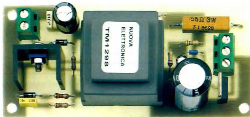
Fig.4 Foto che riproduce il circuito montato. In alto a sinistra potete vedere la morsetteria a due poli per il collegamento alla batteria da 12 Volt oppure ad un alimentatore stabilizzato collegato alla rete dei 230 Volt, in grado di erogare una tensione di 12 Volt con 0,5 Ampere. Come potete notare, il transistor TR1, visibile a sinistra, va applicato sopra una piccola aletta di raffreddamento.
