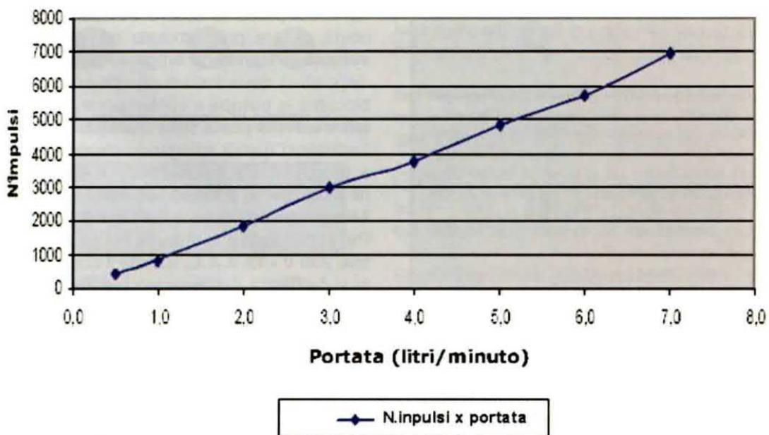
**Fig.17** In figura è riprodotta la curva di risposta del nostro contaltri da 0 a 7 litri/minuto. Sull'asse verticale del grafico è riportato il numero degli impulsi forniti dal contaltri, mentre sull'asse orizzontale è indicata la portata in litri al minuto.
