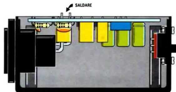
**Fig.7** Con il saldatore ben caldo saldate i tre terminali della presa microfono al circuito stampato. In un montaggio privo di imperfezioni i tre punti di saldatura non devono essere in cortocircuito e le saldature devono avere un aspetto lucido.
