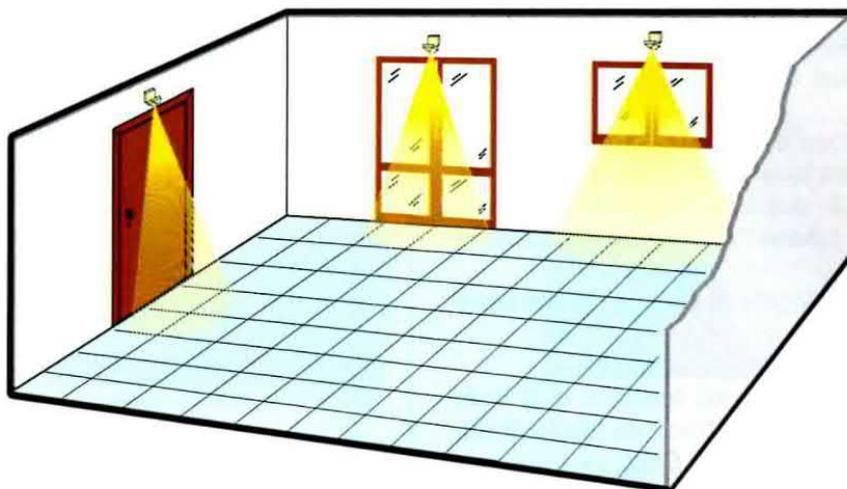
**Fig.3** In questo disegno diamo un esempio di come disporre i sensori, che andranno fissati al di sopra delle porte e delle finestre che si desidera tenere sotto controllo, dirigendo verso il basso il loro cono di azione. In questo modo sarete liberi di muovervi all'interno del locale anche con l'antifurto inserito.
