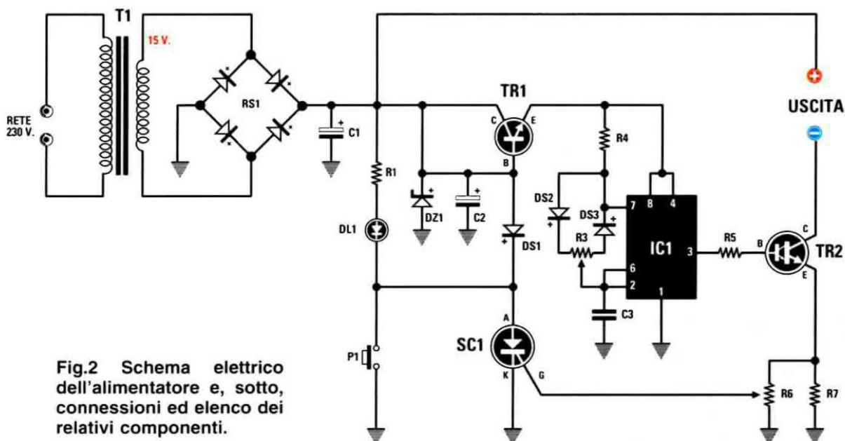
Fig.2 Schema elettrico dell'alimentatore e, sotto, connessioni ed elenco dei relativi componenti.
