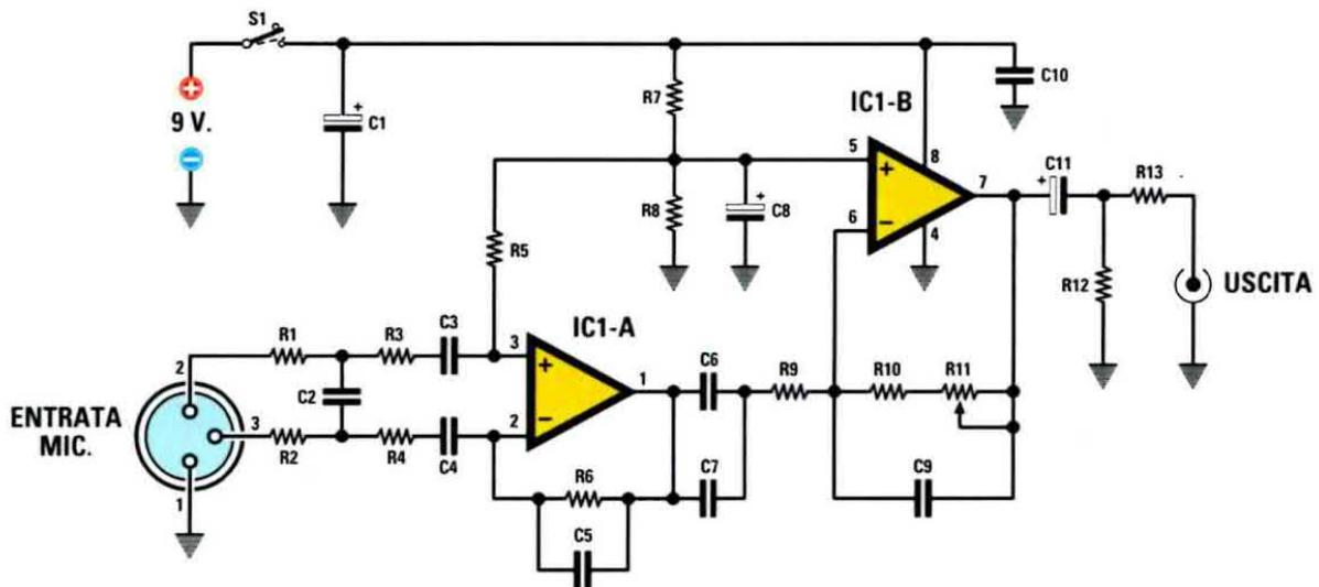
Fig.1 Schema elettrico del preamplificatore per microfono ad uscita bilanciata. Questo circuito converte i segnali bilanciati dei microfoni professionali in segnali sbilanciati adatti ad essere amplificati da un comune impianto hi-fi domestico. Il guadagno del circuito può essere regolato da 0 a 40 dB tramite il trimmer R11.
