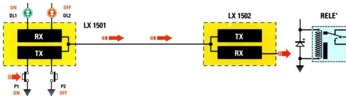
Fig.5 In questo disegno abbiamo esemplificato cosa accade quando nello stadio trasmettente LX.1501 premiamo il pulsante P1-ON: sulla linea della tensione di rete dei 230 Volt viene inviata una serie di impulsi codificata che, captata dallo stadio ricevente LX.1502, provvederà ad eccitare il relè posto all'interno.
