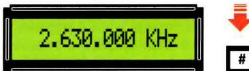
Fig.31 Ogni volta che impostate un nuovo valore di frequenza digitandolo sulla tastiera, per prelevarlo dall'uscita del Generatore UHF dovete premere il tasto #.
