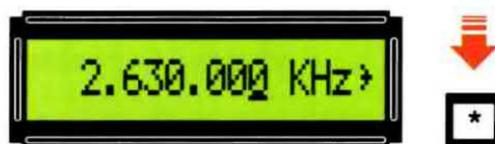
Fig.32 Se volete variare di pochi KHz la frequenza che appare sul Display, dovete premere il tasto \* fino a quando non sarà sottolineato il numero da modificare.
