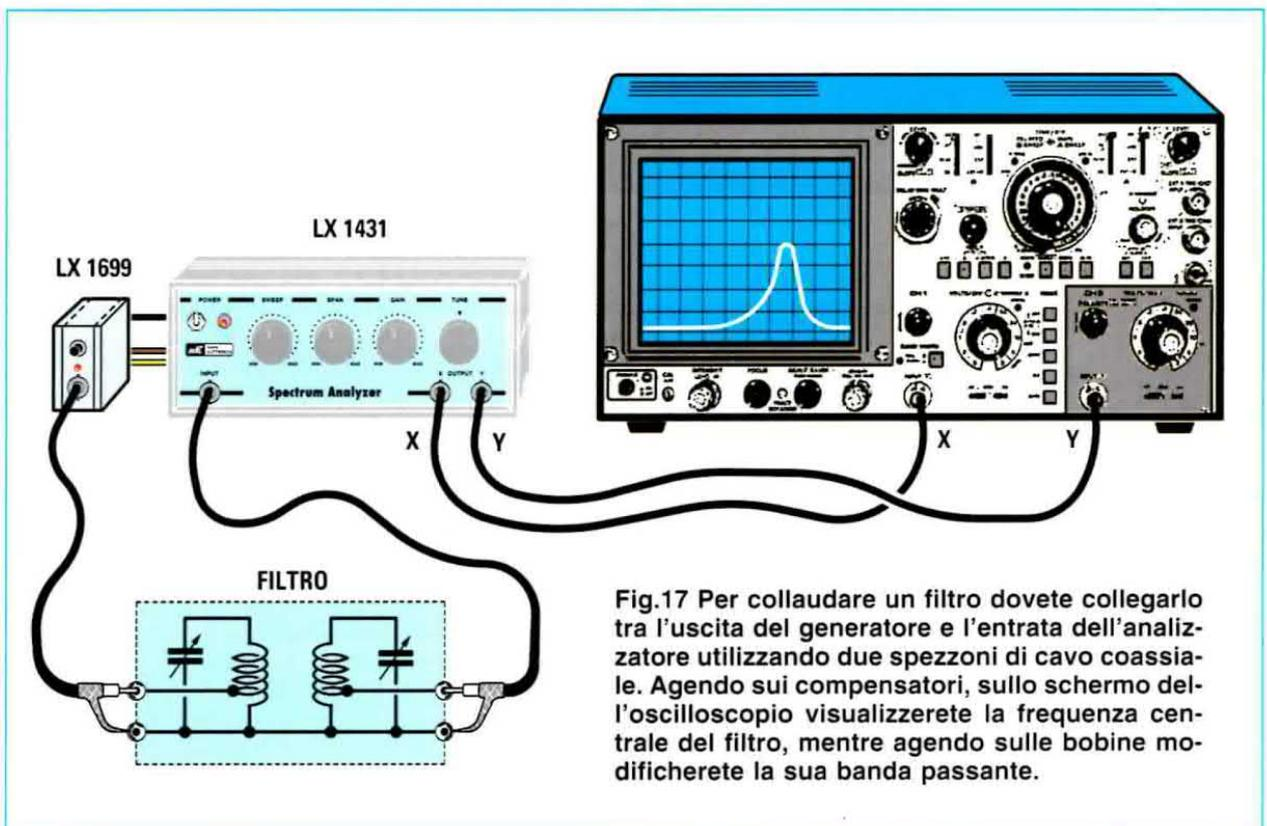
Fig.17 Per collaudare un filtro dovete collegarlo tra l'uscita del generatore e l'entrata dell'analizzatore utilizzando due spezzoni di cavo coassiale. Agendo sui compensatori, sullo schermo dell'oscilloscopio visualizzerete la frequenza centrale del filtro, mentre agendo sulle bobine modificherete la sua banda passante.
