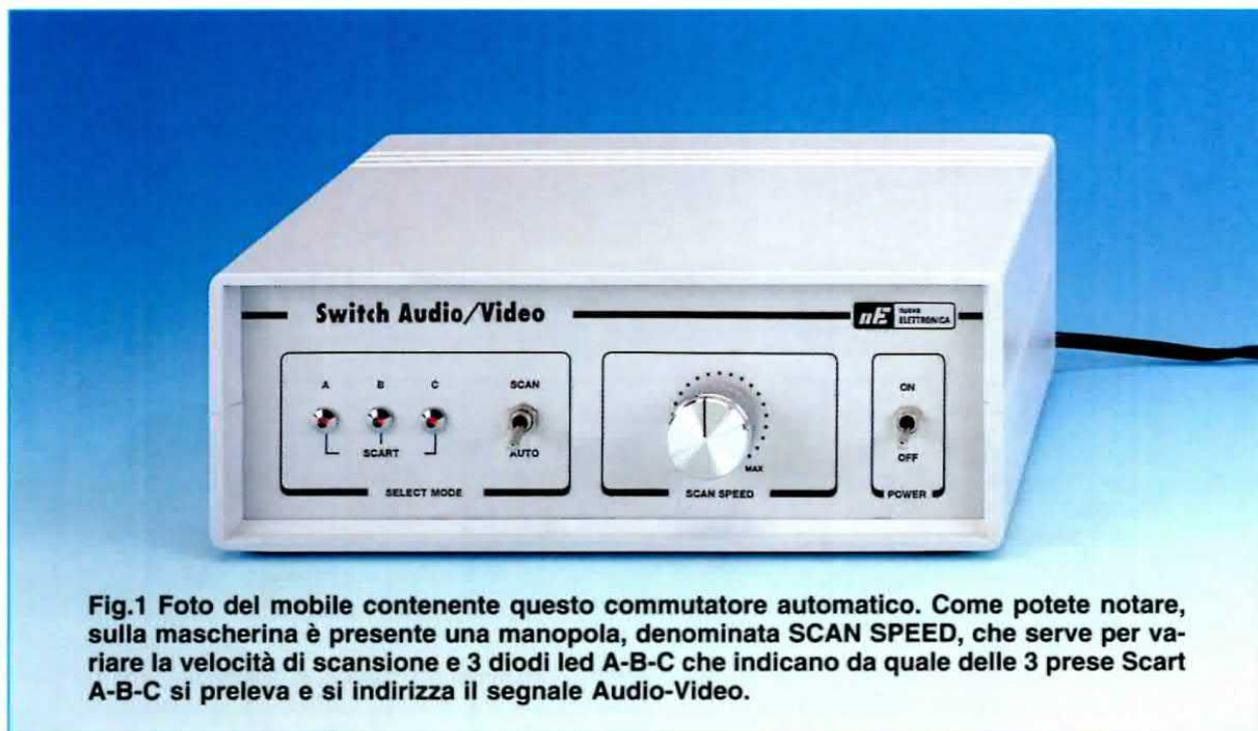
**Fig.1** Foto del mobile contenente questo commutatore automatico. Come potete notare, sulla mascherina è presente una manopola, denominata **SCAN SPEED**, che serve per variare la velocità di scansione e 3 diodi led **A-B-C** che indicano da quale delle 3 prese Scart **A-B-C** si preleva e si indirizza il segnale Audio-Video.
