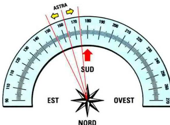
Fig.6 Se ci troviamo a Roma o nelle sue adiacenze e vogliamo direzionare la parabola sul satellite Astra, dovremo posizionarla sui 170° di Azimut ed inclinarla di 41° se è Circolare. Se la parabola risulta di tipo Offset dovremo inclinarla di soli 21°. Ruotando lentamente la parabola da 160° a 180°, aumenteremo l'inclinazione di circa 2° alla volta fino a captare il segnale.
