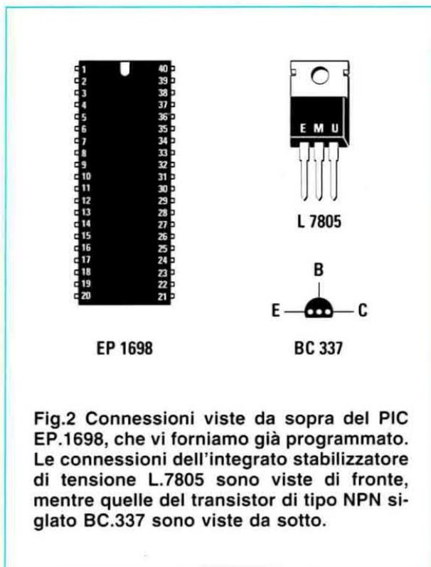
**Fig.2 Connessioni viste da sopra del PIC EP.1698, che vi forniamo già programmato. Le connessioni dell'integrato stabilizzatore di tensione L.7805 sono viste di fronte, mentre quelle del transistor di tipo NPN siglato BC.337 sono viste da sotto.**
