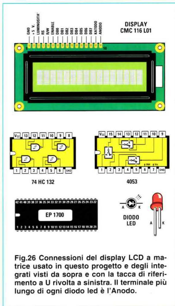
**Fig.26** Connessioni del display LCD a matrice usato in questo progetto e degli integrati visti da sopra e con la tacca di riferimento a U rivolta a sinistra. Il terminale più lungo di ogni diodo led è l'Anodo.
