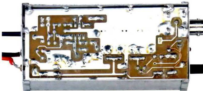
Proseguite saldando le **bobine** precedentemente avvolte ed anche l'impedenza **JAF1**.
