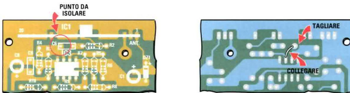
Fig.4 Prima di iniziare a saldare i componenti sul circuito stampato LX.1475, isolate la pista del condensatore al poliestere C6 che si collega al piedino 3 dell'integrato IC3 e con un ponticello collegate il condensatore al piedino non invertente 2 dello stesso integrato.
