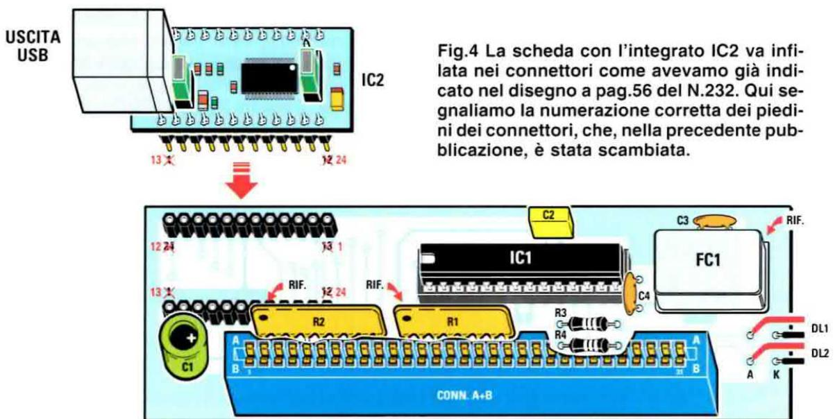
Fig.4 La scheda con l'integrato IC2 va infilata nei connettori come avevamo già indicato nel disegno a pag.56 del N.232. Qui segnaliamo la numerazione corretta dei piedini dei connettori, che, nella precedente pubblicazione, è stata scambiata.
