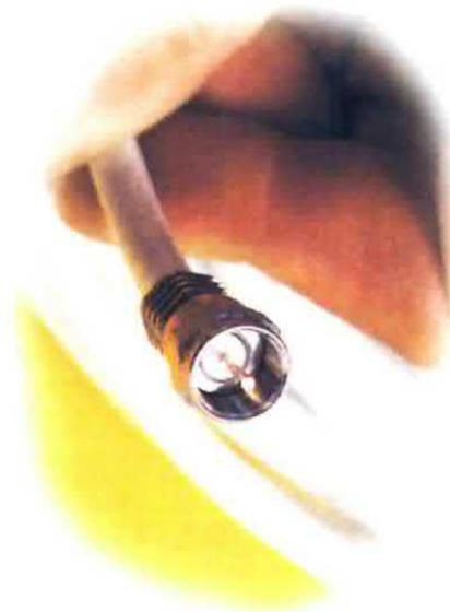
Fig.2 Infilato il connettore "F", dal centro del corpo uscirà il filo di rame del cavo coassiale (vedi il disegno F in fig.4).
