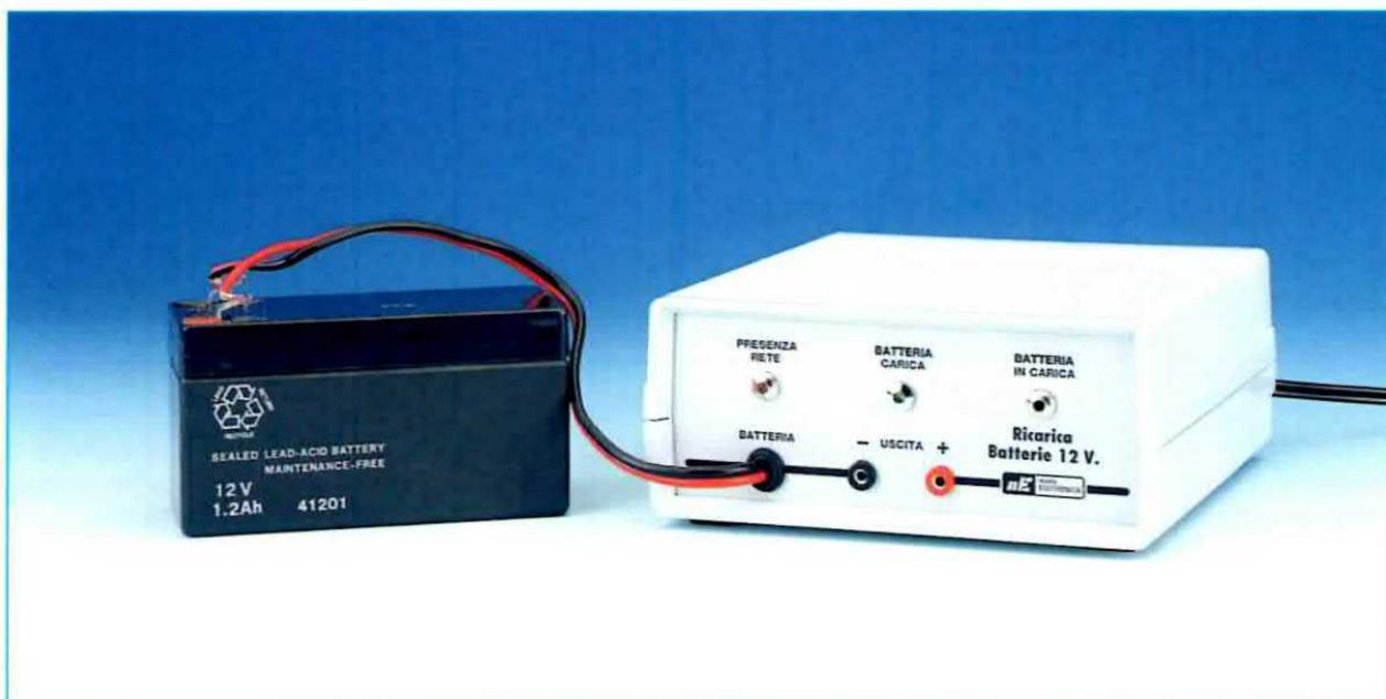
**Fig.1** Per tenere accesa una lampadina da 12 Volt per un paio d'ore, potete utilizzare una piccola batteria da 1,2 Ah. Sotto, come si presenta il circuito stampato a montaggio ultimato ed inserito nel mobile plastico ad esso destinato.
