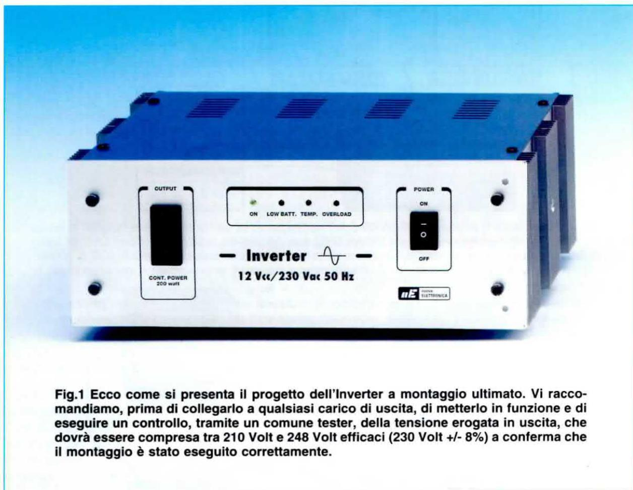
**Fig.1** Ecco come si presenta il progetto dell'Inverter a montaggio ultimato. Vi raccomandiamo, prima di collegarlo a qualsiasi carico di uscita, di metterlo in funzione e di eseguire un controllo, tramite un comune tester, della tensione erogata in uscita, che dovrà essere compresa tra 210 Volt e 248 Volt efficaci (230 Volt +/- 8%) a conferma che il montaggio è stato eseguito correttamente.
