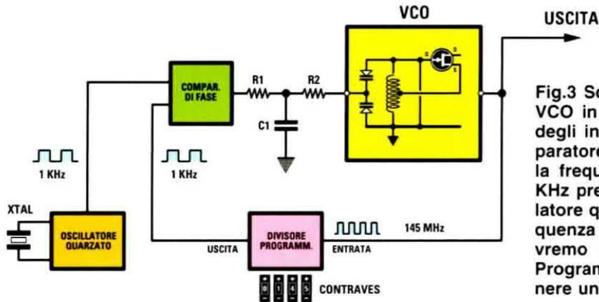
Fig.3 Schema semplificato di un VCO in tecnologia PLL. Ad uno degli ingressi dello stadio Comparatore di Fase viene applicata la frequenza di riferimento di 1 KHz prelevata dallo stadio oscillatore quarzato e nell'altro la frequenza prelevata dal VCO, che avremo diviso con un Divisore Programmabile in modo da ottenere una frequenza di 1 KHz.
