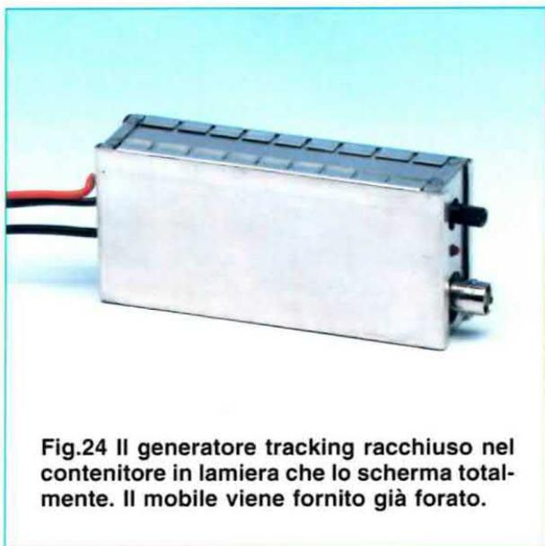
Fig.24 Il generatore tracking racchiuso nel contenitore in lamiera che lo schermava totalmente. Il mobile viene fornito già forato.
