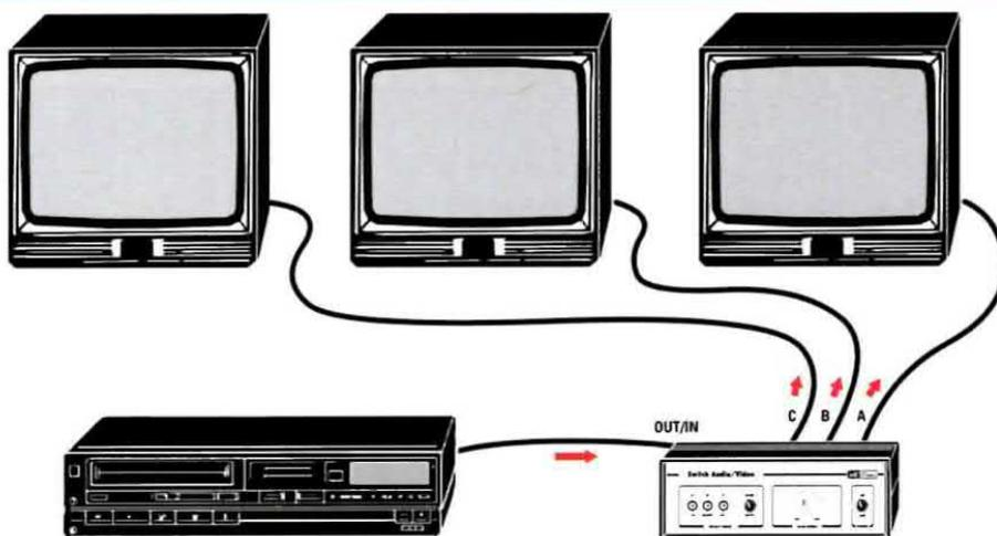
**Fig.2** Prelevando il segnale Audio-Video dall'uscita Scart di un Ricevitore per satelliti oppure di un Videoregistratore o di un lettore DVD e applicandola sulla presa Scart OUT-IN del commutatore, il segnale verrà automaticamente trasferito sulle prese secondarie A-B-C, quindi potrà essere visualizzato su tre diversi televisori provvisti di una presa d'ingresso Scart.
