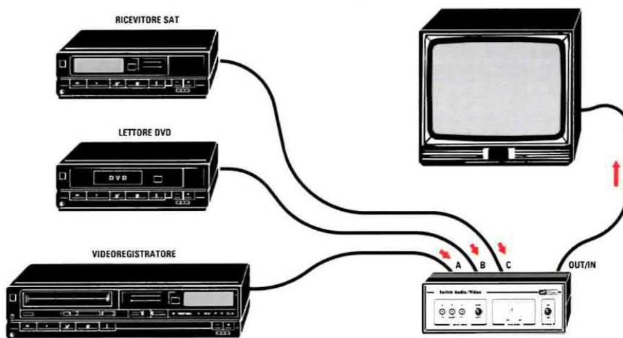
**Fig.3** Per trasferire il segnale Audio-Video presente sull'uscita di 3 diverse apparecchiature ad un solo televisore, è necessario collegare quest'ultimo alla presa Scart primaria OUT-IN. Il segnale che appare sul TV sarà quello dell'apparecchio secondario che risulta in funzione.
