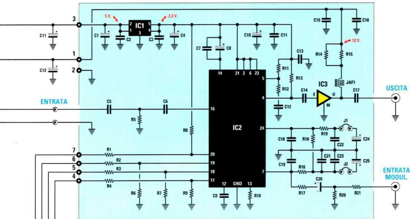
Fig.9 Schema elettrico del Generatore UHF siglato LX.1700. Il riquadro colorato in alto a sinistra siglato KM1644 corrisponde alla scheda sulla quale è saldato il DDS AD.9951 (vedi fig.2), mentre quello a destra siglato KM1644B corrisponde alla scheda sulla quale è saldato l'integrato Synthesizer ADF.4360-0 (vedi fig.1).
