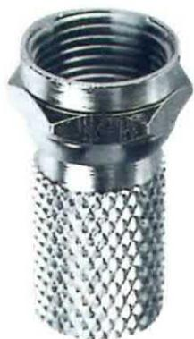
Fig.1 Come potete vedere in questa figura, il connettore maschio "F" è un piccolo tubetto forato. Sulla parte superiore è presente un dado per avvitarlo sul connettore femmina di un convertitore LNB oppure di un Decoder, come visibile in fig.3. Questo connettore tipo "F" maschio va applicato direttamente sul Cavo Coassiale (vedi fig.4) seguendo le indicazioni riportate nell'articolo. Il costo dei connettori maschio tipo "F" è di circa 1 Euro.
