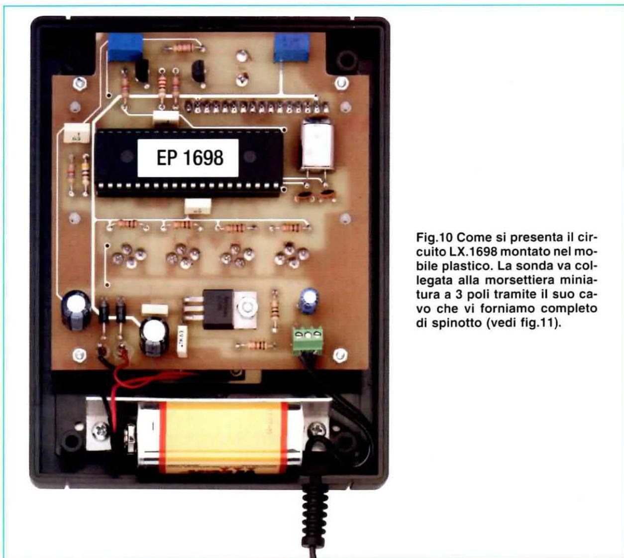
Fig.10 Come si presenta il circuito LX.1698 montato nel mobile plastico. La sonda va collegata alla morsettiera miniatura a 3 poli tramite il suo cavo che vi forniamo completo di spinotto (vedi fig.11).
