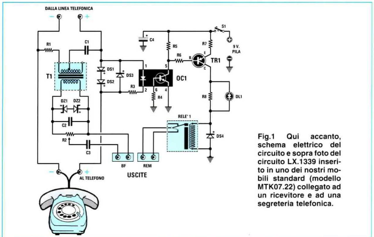
Fig.1 Qui accanto, schema elettrico del circuito e sopra foto del circuito LX.1339 inserito in uno dei nostri mobili standard (modello MTK07.22) collegato ad un ricevitore e ad una segreteria telefonica.
