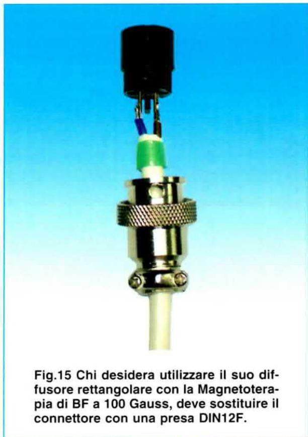
Fig.15 Chi desidera utilizzare il suo diffusore rettangolare con la Magnetoterapia di BF a 100 Gauss, deve sostituire il connettore con una presa DIN12F.
