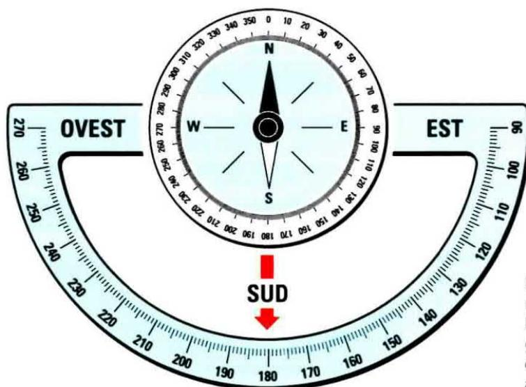
Fig.2 Per evitare errori si preferisce utilizzare i gradi di Azimut. In possesso di un goniometro rivolghiamo i suoi 180° sul punto Sud, così ritroviamo a 90° il punto Est e a 270° il punto Ovest.
