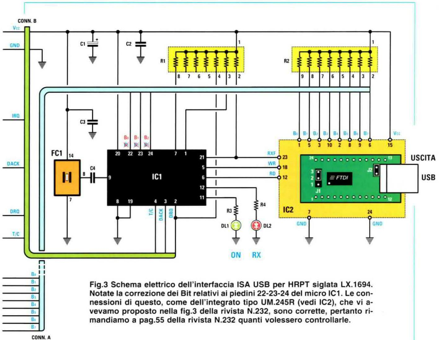
Fig.3 Schema elettrico dell'interfaccia ISA USB per HRPT siglata LX.1694. Notate la correzione dei Bit relativi ai piedini 22-23-24 del micro IC1. Le connessioni di questo, come dell'integrato tipo UM.245R (vedi IC2), che vi avevamo proposto nella fig.3 della rivista N.232, sono corrette, pertanto rimandiamo a pag.55 della rivista N.232 quanti volessero controllarle.
