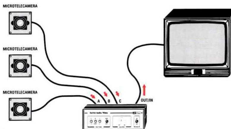
**Fig.4** Questo commutatore permette anche di visualizzare in modo sequenziale su un televisore oppure su un monitor, i segnali Video captati dalle microtelecamere installate in punti diversi di un locale. Questa funzione può essere utilizzata nei supermercati per evitare furti e scippi oppure per controllare ingressi o parchi auto.
