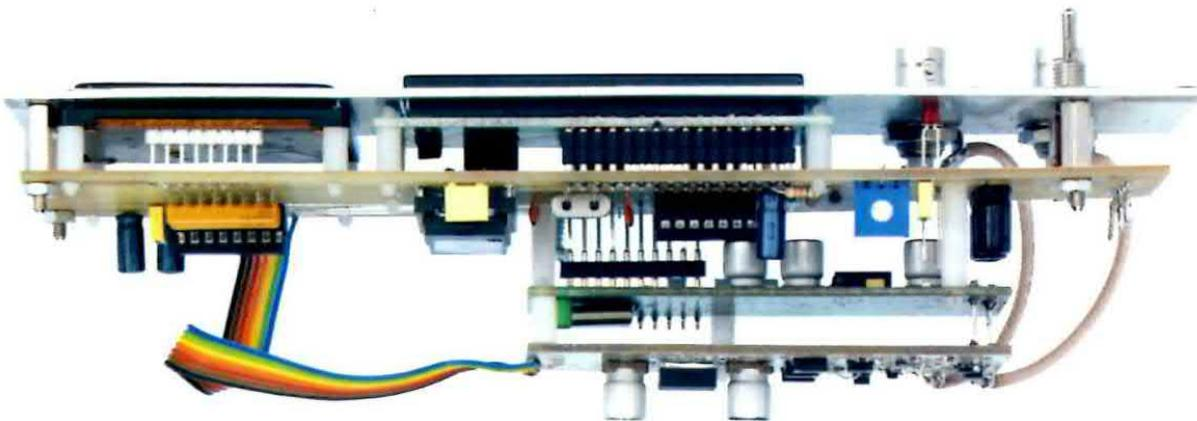
Fig.24 Foto del circuito stampato base LX.1700 con innestate le due schede in SMD premontate KM1644 e KM1644B. I quattro distanziatori metallici che trovate nel kit vanno avvitate sui perni presenti sul pannello frontale, poi su questi viene applicato il circuito stampato LX.1700 e le schede premontate KM1644 e KM1644B.
