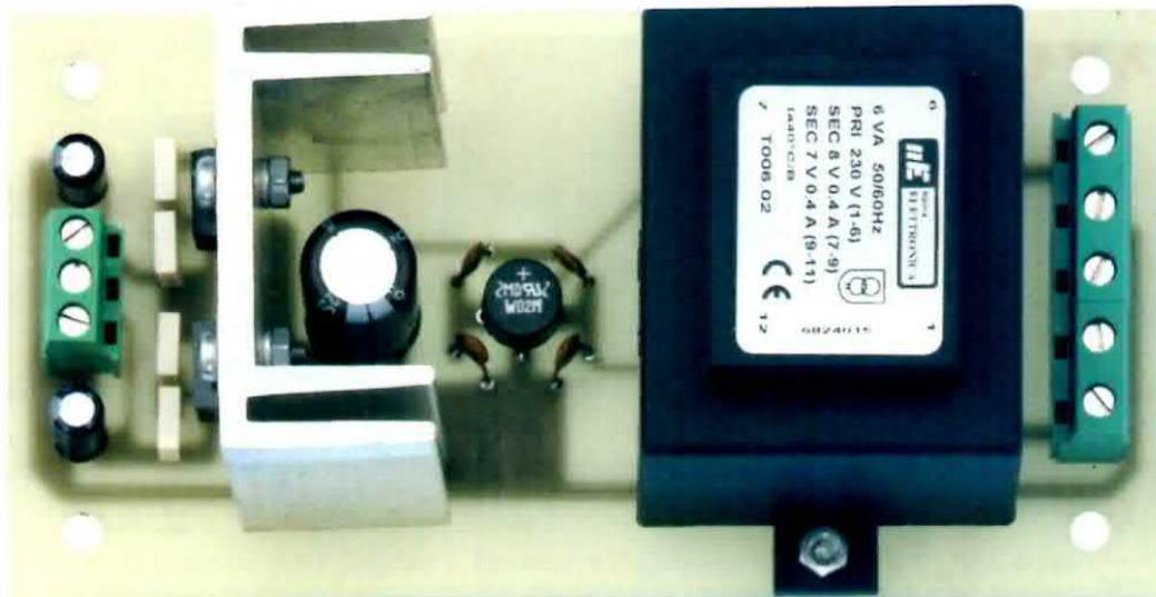
Fig.11 In alto la foto dello stadio di alimentazione LX.1701 ed in basso lo schema pratico di montaggio. I fili che escono dalle morsettiere di sinistra e di destra si collegano al circuito stampato LX.1700 visibile in fig.18. L'interruttore di accensione (vedi S1 in fig.10) va montato sulla scheda LX.1700.
