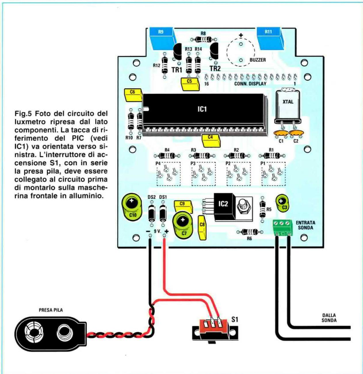
Fig.5 Foto del circuito del luxmetro ripresa dal lato componenti. La tacca di riferimento del PIC (vedi IC1) va orientata verso sinistra. L'interruttore di accensione S1, con in serie la presa pila, deve essere collegato al circuito prima di montarlo sulla mascherina frontale in alluminio.
