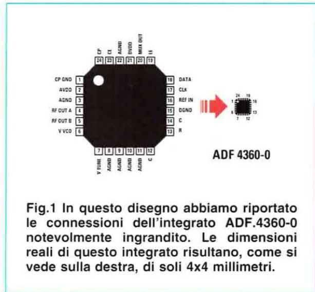
Fig.1 In questo disegno abbiamo riportato le connessioni dell'integrato ADF.4360-0 notevolmente ingrandito. Le dimensioni reali di questo integrato risultano, come si vede sulla destra, di soli 4x4 millimetri.
