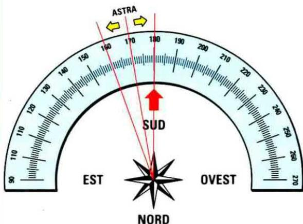
Fig.7 Se ci troviamo a Lecce o nelle sue vicinanze e vogliamo direzionare la parabola sul satellite Astra, dovremo posizionarla sui 178° di Azimut con una Elevazione di 43° se risulta Circolare, e con una Elevazione di circa 23° se è di tipo Offset. Come spiegato, cambiando l'elevazione di circa 2° ogni volta, ruoteremo la parabola da 168° a 188° fino a centrare il segnale.
