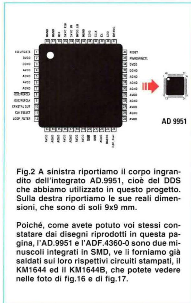
Fig.2 A sinistra riportiamo il corpo ingrandito dell'integrato AD.9951, cioè del DDS che abbiamo utilizzato in questo progetto. Sulla destra riportiamo le sue reali dimensioni, che sono di soli 9x9 mm.
