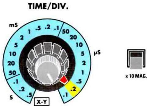
**Fig.9** Per eseguire la misura dovete sincerarvi che il selettore della Base dei tempi del vostro oscilloscopio possa arrivare alla portata di .2 (0,2) microsecondi, corrispondenti a 200 nanosecondi. Attivando poi il comando x10 MAG potrete espandere ulteriormente di 10 volte la Base dei tempi, arrivando così ad una risoluzione di 20 nanosecondi per ciascun quadretto.
