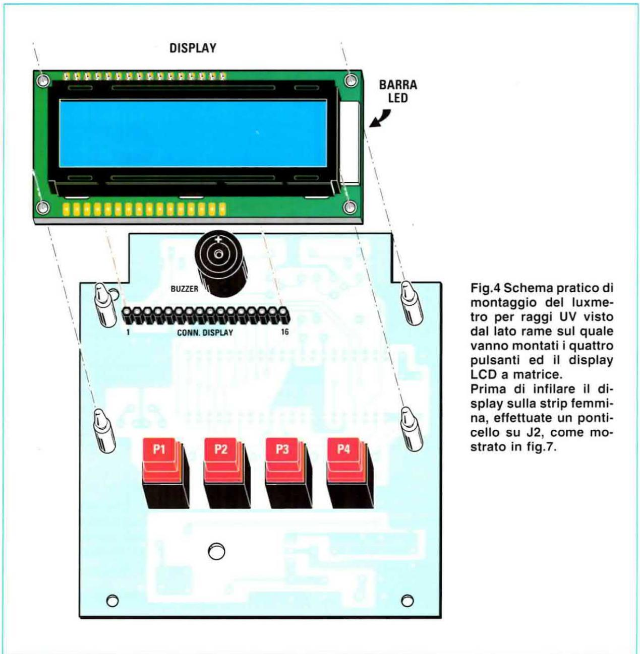
Fig.4 Schema pratico di montaggio del luxmetro per raggi UV visto dal lato rame sul quale vanno montati i quattro pulsanti ed il display LCD a matrice. Prima di infilare il display sulla strip femmina, effettuate un ponticello su J2, come mostrato in fig.7.
