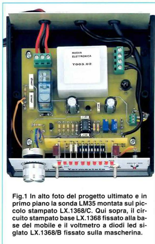
Fig.1 In alto foto del progetto ultimato e in primo piano la sonda LM35 montata sul piccolo stampato LX.1368/C. Qui sopra, il circuito stampato base LX.1368 fissato alla base del mobile e il voltmetro a diodi led siglato LX.1368/B fissato sulla mascherina.
