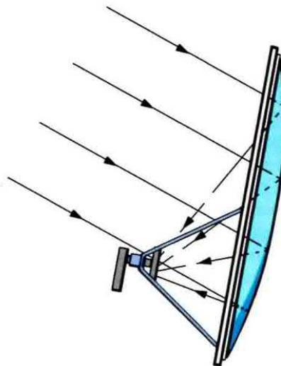
**Fig.4** Le parabole Offset, che sono le più utilizzate, hanno una forma Ovale. Poiché il segnale del satellite viene riflesso sulla parte bassa della parabola, il suo punto focale risulta spostato verso il basso. Questa parabola andrà inclinata di circa 20° in meno rispetto ai gradi di Elevazione trascritti nella Tabella a fine articolo.
