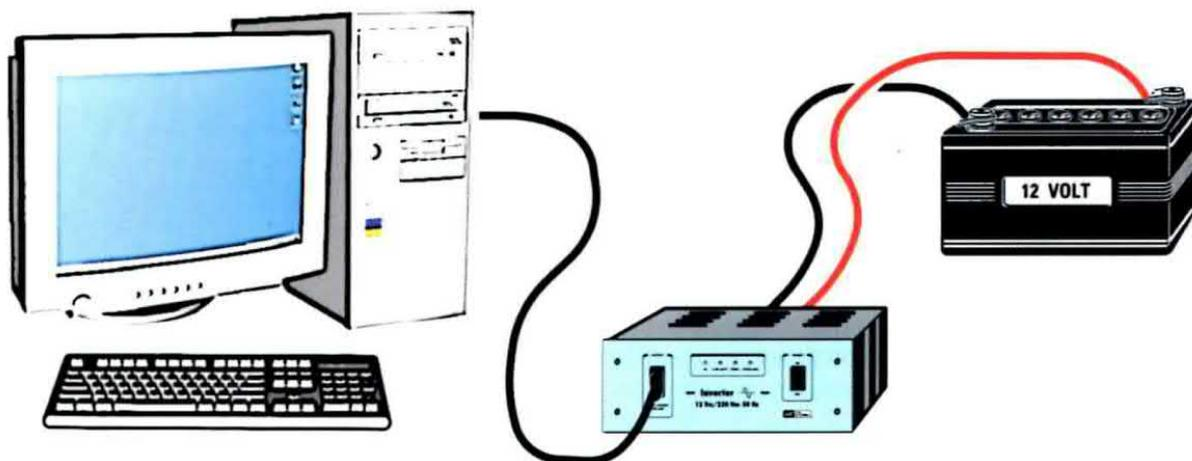
**Fig.3** Collegando l'inverter ad una normale batteria da automobile potrete proteggere il vostro personal computer da fastidiosi disturbi di rete. La batteria potrà essere ricaricata con il nostro caricabatteria siglato **LX.1623**, pubblicato nella rivista **N.224**.
