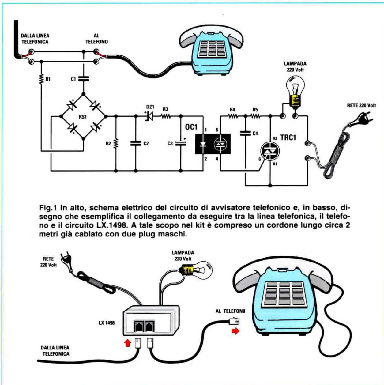
Fig.1 In alto, schema elettrico del circuito di avvisatore telefonico e, in basso, disegno che esemplifica il collegamento da eseguire tra la linea telefonica, il telefono e il circuito LX.1498. A tale scopo nel kit è compreso un cordone lungo circa 2 metri già cablato con due plug maschi.
