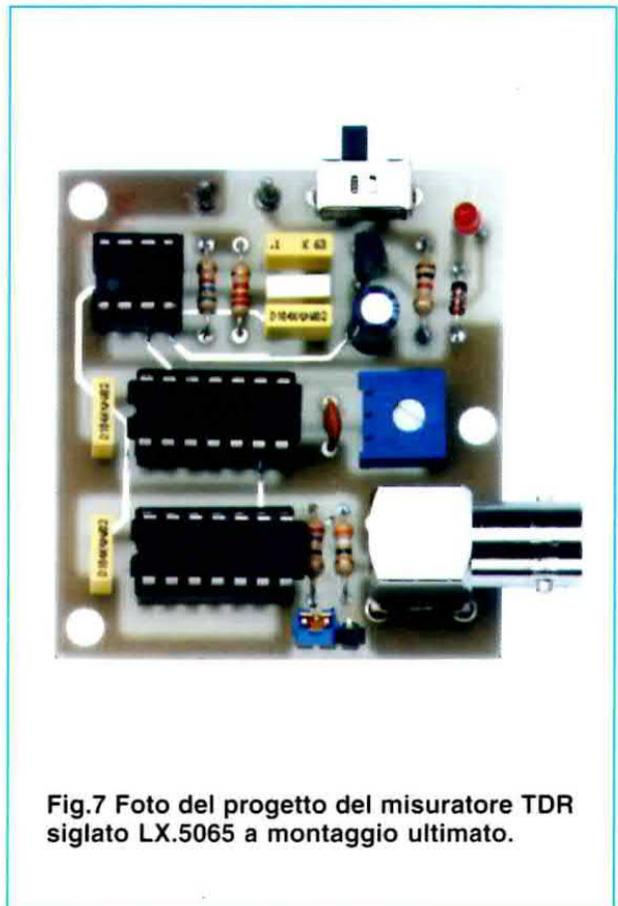
Fig.7 Foto del progetto del misuratore TDR siglato LX.5065 a montaggio ultimato.
