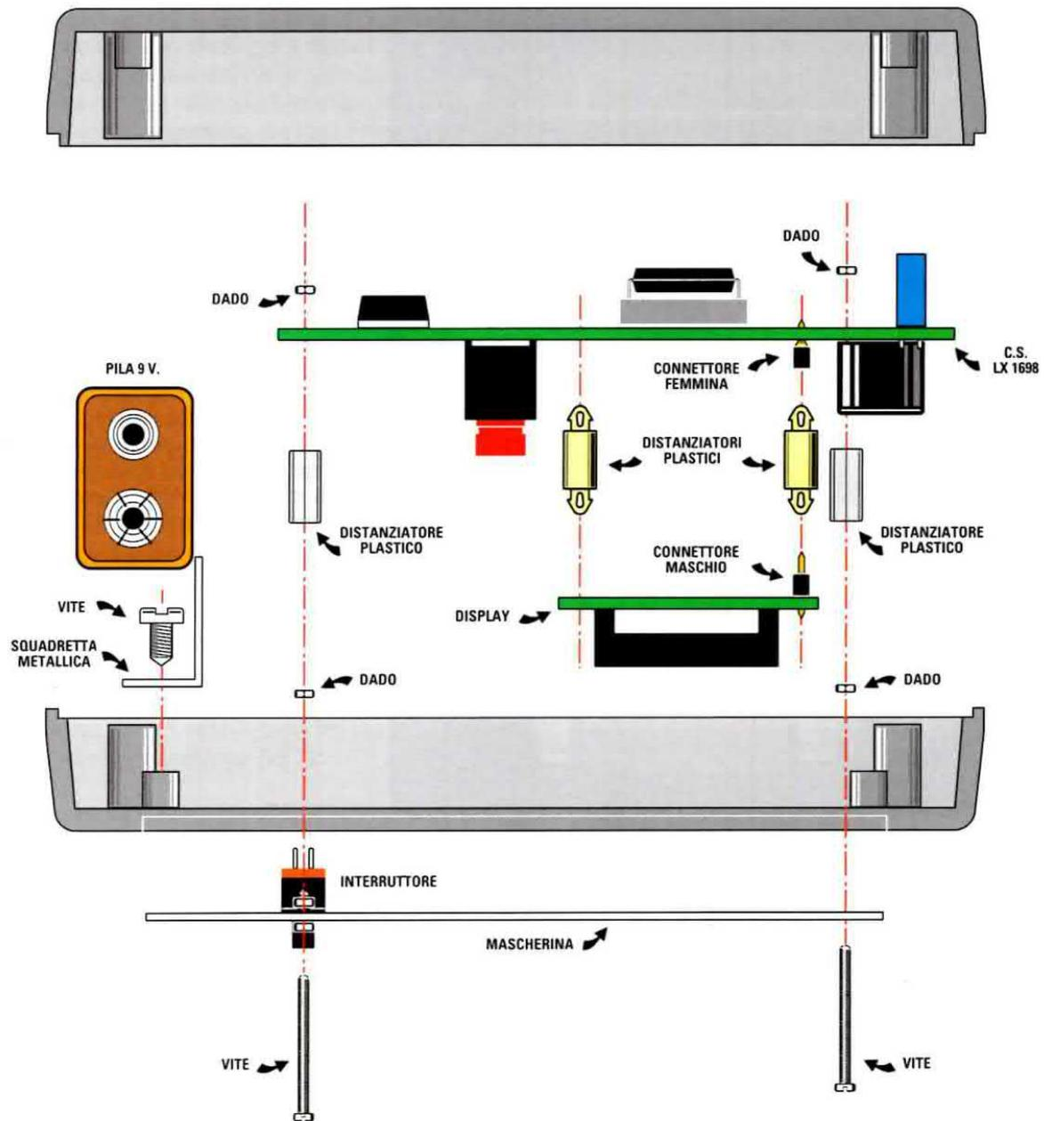
Fig.9 Esploso del montaggio del luxmetro per raggi UV nel suo mobile plastico. Si tratta di uno strumento compatto e tascabile, che racchiude al suo interno tutta la circuiteria.
