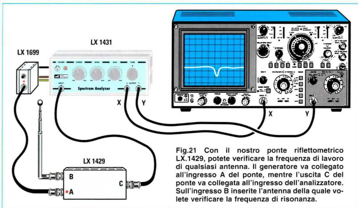
Fig.21 Con il nostro ponte riflettometrico LX.1429, potete verificare la frequenza di lavoro di qualsiasi antenna. Il generatore va collegato all'ingresso A del ponte, mentre l'uscita C del ponte va collegata all'ingresso dell'analizzatore. Sull'ingresso B inserite l'antenna della quale volete verificare la frequenza di risonanza.
