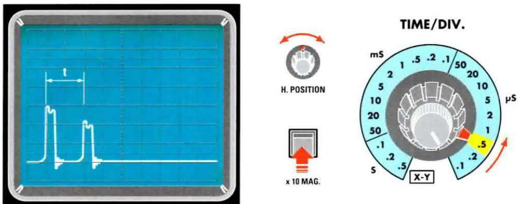
Fig.16 Se non vi riesce di fare riapparire gli impulsi sullo schermo dovrete ruotare il selettore TIME/DIV. in senso antiorario, posizionandolo sulla portata .5 (0,5) microsecondi. Agendo ancora sul comando Horizontal position sarete in grado di far apparire gli impulsi sullo schermo.
