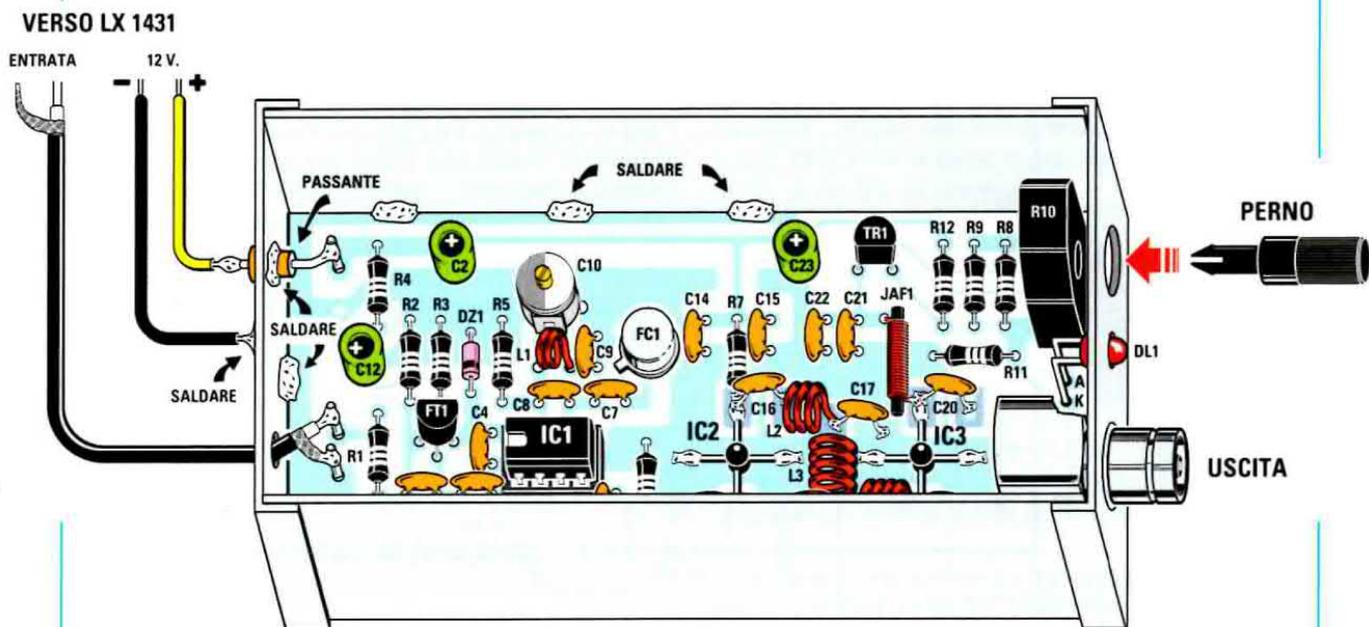
Fig.8 Il generatore tracking va collocato nel mobile di lamiera che vi forniamo già forato e che ha il compito di schermare il circuito dai disturbi esterni. Per questo motivo lo stampato va saldato direttamente al mobile. Per il ramo positivo dell'alimentazione si è utilizzato un passante, mentre il negativo è derivato direttamente dal contenitore.
