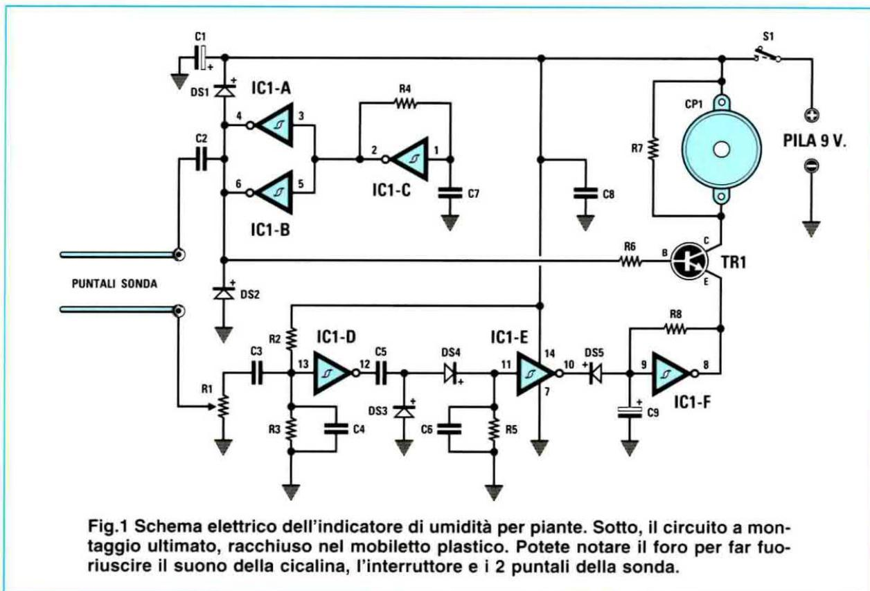
Fig.1 Schema elettrico dell'indicatore di umidità per piante. Sotto, il circuito a montaggio ultimato, racchiuso nel mobiletto plastico. Potete notare il foro per far fuoriuscire il suono della cicalina, l'interruttore e i 2 puntali della sonda.
