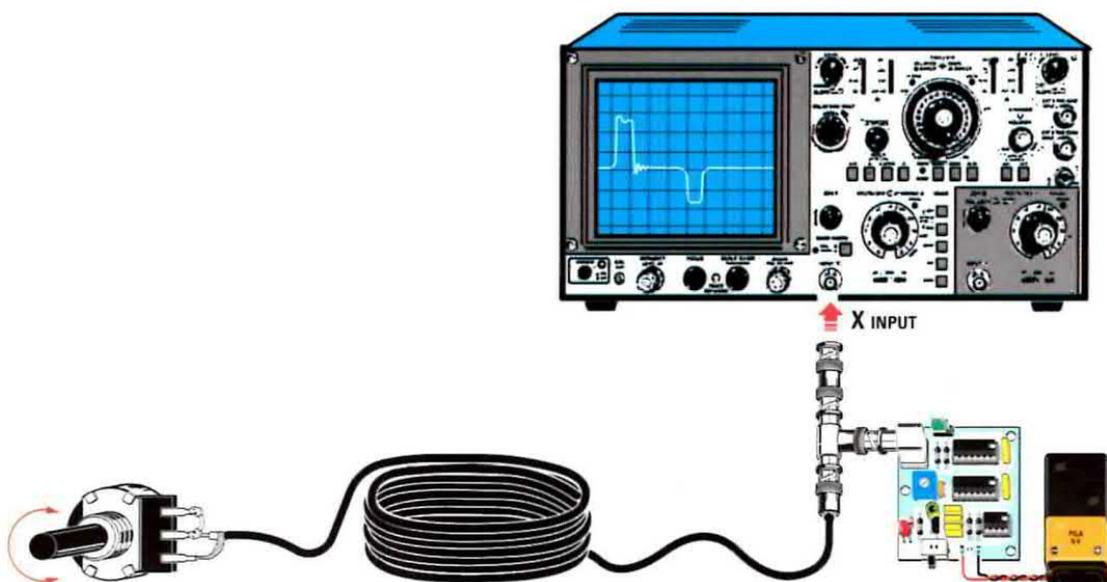
**Fig.4** Un'altra interessante misura che potrete eseguire con il circuito LX.5065 è quella della impedenza di un cavo sconosciuto. Per ricavare l'impedenza di un cavo coassiale è sufficiente infatti collegare alla sua estremità un potenziometro del valore di 100 ohm. Ruotando tale potenziometro ed osservando come si modifica il tracciato sull'oscilloscopio, sarete in grado di misurare con precisione l'impedenza di qualsiasi tipo di cavo coassiale.
