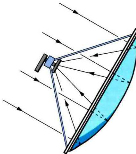
**Fig.3** Le parabole a Primo Fuoco hanno una forma Circolare ed il convertitore LNB risulta sempre posto sul loro punto focale, che si trova al centro della parabola. Queste parabole vanno inclinate sui gradi di Elevazione riportati nella Tabella a fine articolo in corrispondenza della città in cui si risiede e del satellite prescelto.
