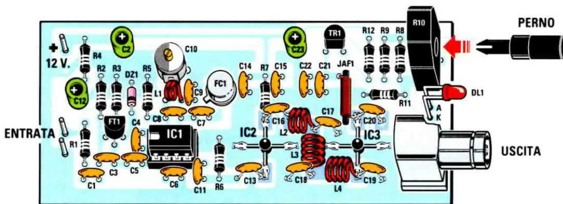
**Fig.7** Schema pratico di montaggio del generatore tracking siglato LX.1699. Sulla destra potete vedere il trimmer R10, dotato di un pratico perno così da poterlo manovrare con le dita senza dover usare alcun cacciavite. Lo abbiamo voluto esterno al contenitore (vedi fig.24) perché vi serve per regolare la potenza del segnale in uscita.
