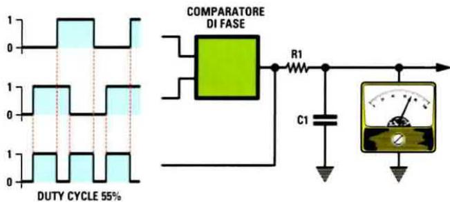
Fig.5 Se la frequenza del VCO dovesse "scendere", dall'uscita del Comparatore di Fase usciranno delle onde quadre con un duty cycle del 55%, che farà aumentare la tensione ai capi di C1 e poiché questa alimenta i diodi Varicap del VCO, la sua frequenza inizierà ad aumentare fino a raggiungere un duty cycle del 50% (vedi fig.4).
