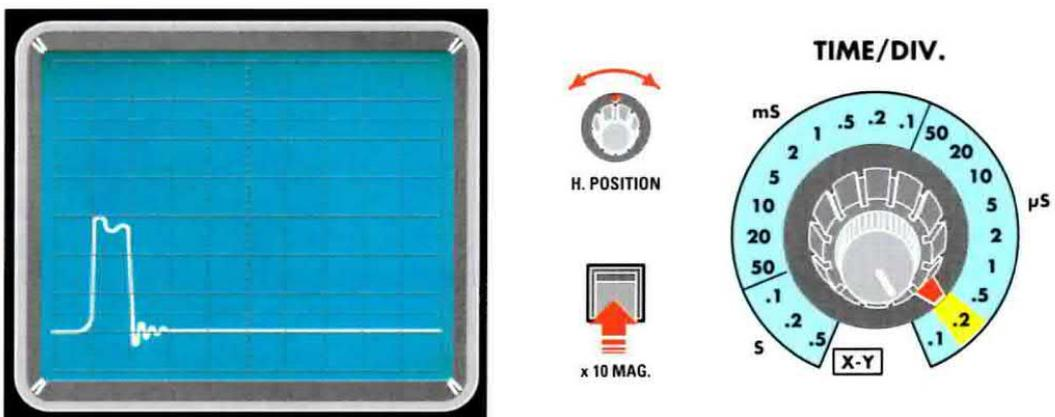
Fig.17 Poiché la distanza in quadretti, e cioè il tempo che separa l'impulso riflesso dall'impulso di partenza dipende dalla lunghezza del cavo, potrebbe accadere che misurando una matassa di cavo di una certa lunghezza l'impulso riflesso non risulti visibile sullo schermo perché troppo distanziato. In questo caso dovrete ruotare il selettore TIME/DIV. sulla portata immediatamente superiore, come indicato nella figura seguente e vedrete apparire entrambi gli impulsi.
