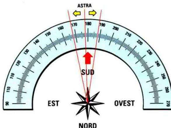
Fig.8 Se sull'asta di una parabola applichiamo due convertitori LNB leggermente divaricati a V, potremo captare due satelliti che abbiano all'incirca gli stessi gradi di elevazione.
