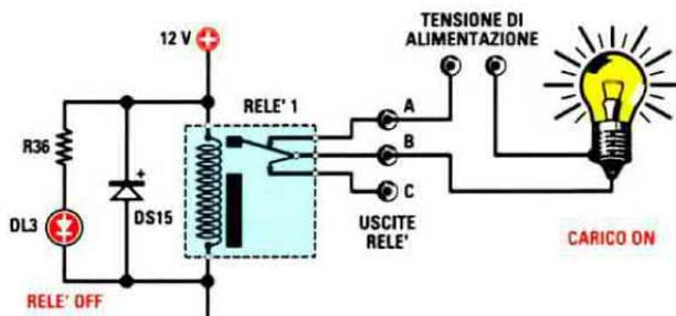
Fig.12 Quando il relè è disattivato, i contatti A-B risultano chiusi, quindi il carico ad essi collegato è alimentato. Nel nostro caso la lampadina è accesa.
