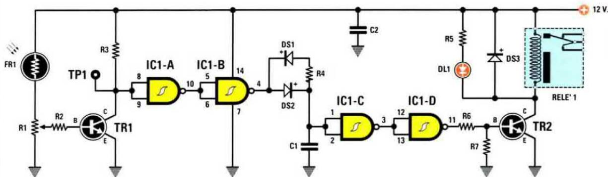
Fig.4 Il relè si eccita quando la fotoresistenza FR1 viene totalmente oscurata. La sensibilità al buio si regola ruotando il cursore del trimmer R1 (vedi testo).
