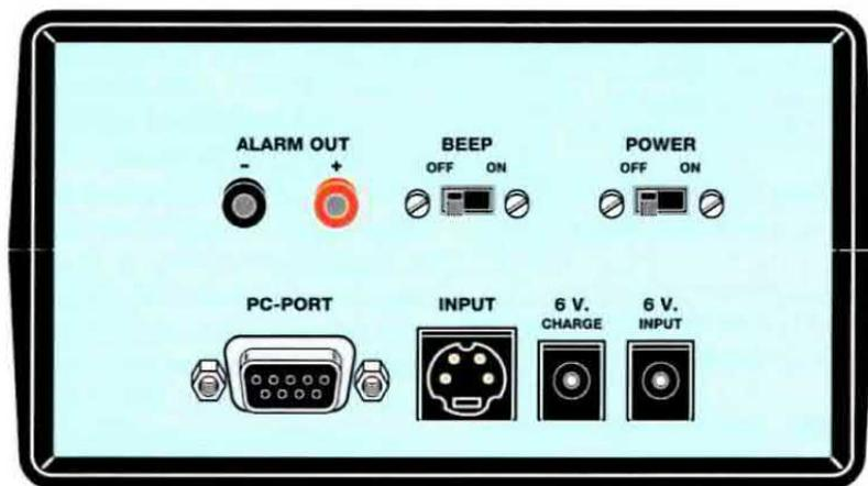
Fig.40 In questo disegno è riprodotta la mascherina posteriore del mobile del contatore Geiger. Potete notare la presenza di una serie di connettori e di due interruttori la cui funzione è descritta sinteticamente nella legenda.
