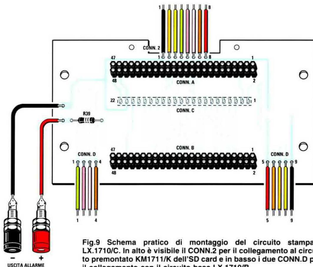
**Fig.9 Schema pratico di montaggio del circuito stampato LX.1710/C.** In alto è visibile il CONN.2 per il collegamento al circuito premontato KM1711/K dell'SD card e in basso i due CONN.D per il collegamento con il circuito base LX.1710/B. Alle due piazzole presenti a sinistra andranno collegate le due boccole del segnale di allarme presenti sul pannello posteriore.
