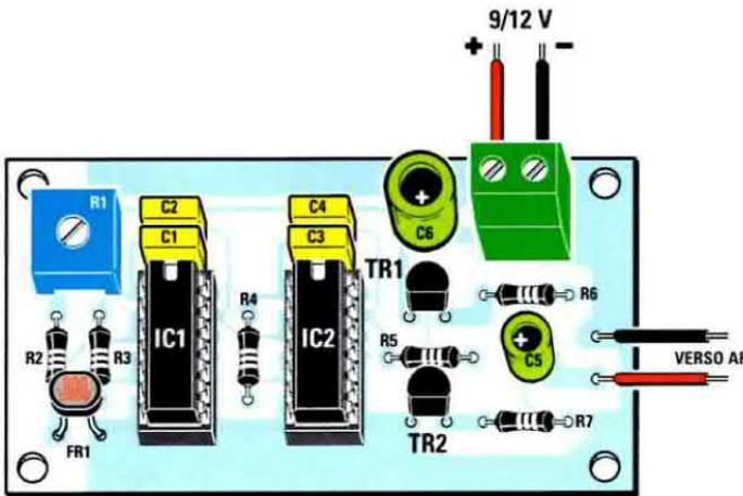
Fig.2 Come disporre tutti i componenti sullo stampato LX.5066. Le tacche di riferimento ad U degli integrati IC1-IC2 vanno rivolte verso l'alto, mentre la parte piatta dei transistor TR1-TR2 va rivolta verso il basso.
