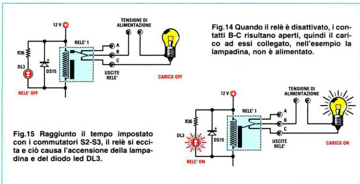
Fig.14 Quando il relè è disattivato, i contatti B-C risultano aperti, quindi il carico ad essi collegato, nell'esempio la lampadina, non è alimentato.
