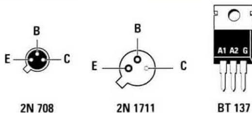
Fig.15 Connessioni E-B-C dei transistor 2N.708 e 2N.1711 viste da sotto, quelle del diodo triac BT.137 sono viste di fronte.
