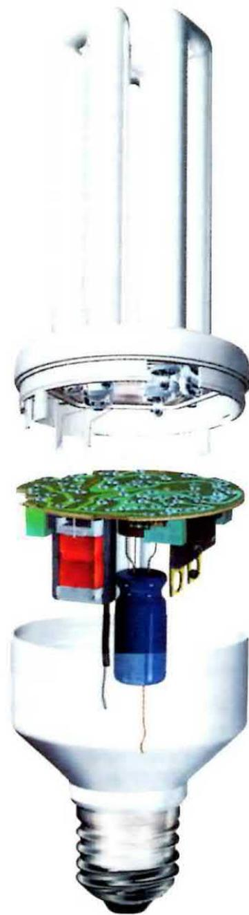
**Fig.6** Le lampade fluorescenti costano molto di più delle lampade a filamento, perché nel loro attacco è inserito un circuito elettronico necessario per assicurare un'accensione istantanea e per stabilizzare la corrente di assorbimento. Quello stesso circuito elimina tutti i disturbi RF ed anche lo sfarfallio.
