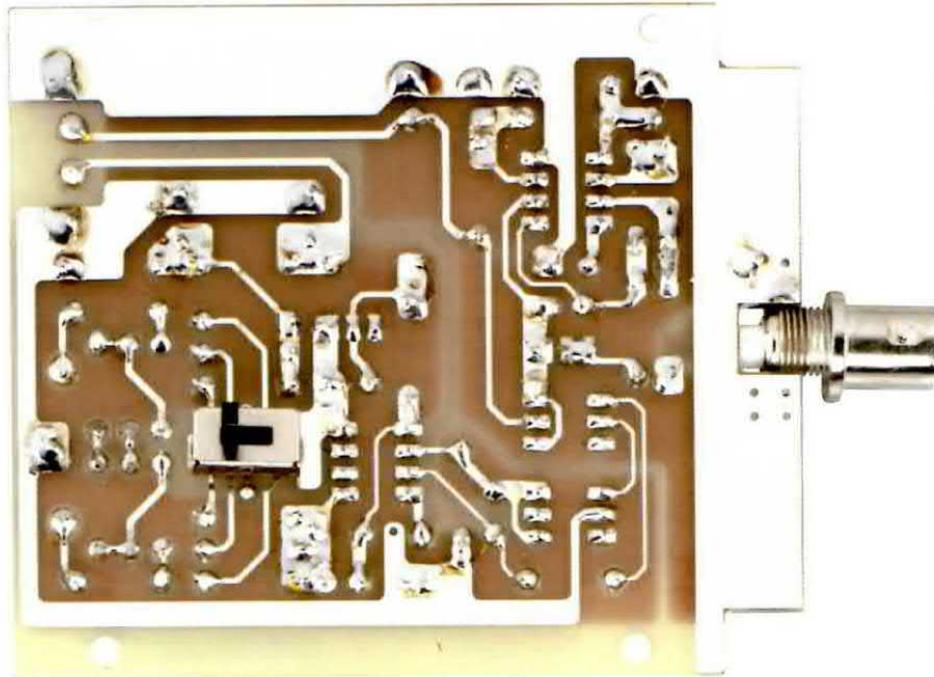
**Fig.3** Foto della sonda differenziale optoisolata ripresa dal lato rame. Su questo lato dovete inserire solo il deviatore a due vie tre posizioni (vedi S2/A-S2/B in fig.6) che permette di attenuare il segnale in ingresso di 10, 100 o 1000 volte.
