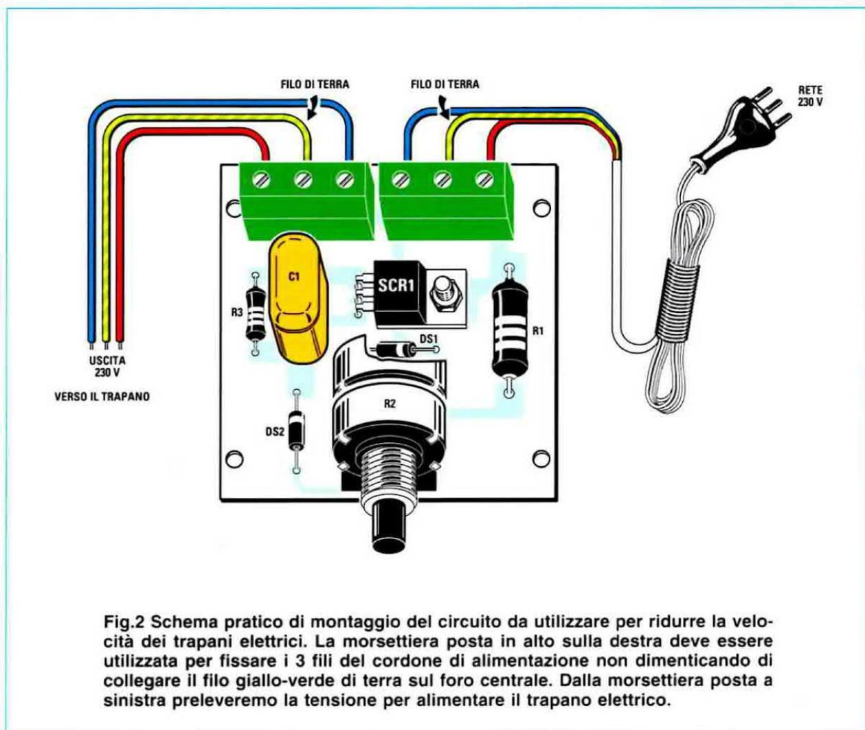
**Fig.2** Schema pratico di montaggio del circuito da utilizzare per ridurre la velocità dei trapani elettrici. La morsettiere posta in alto sulla destra deve essere utilizzata per fissare i 3 fili del cordone di alimentazione non dimenticando di collegare il filo giallo-verde di terra sul foro centrale. Dalla morsettiere posta a sinistra preleveremo la tensione per alimentare il trapano elettrico.
