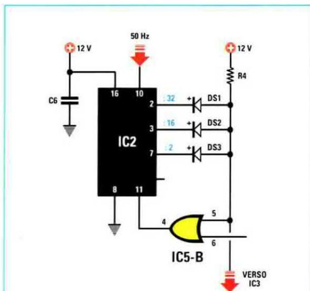
**Fig.2** Per ottenere 1 impulso al secondo partendo dai 50 Hz della rete applicati sul piedino 10, bisogna collegare i diodi al silicio sui piedini 2-3-7, perché la somma dei loro pesi dà come risultato proprio:
