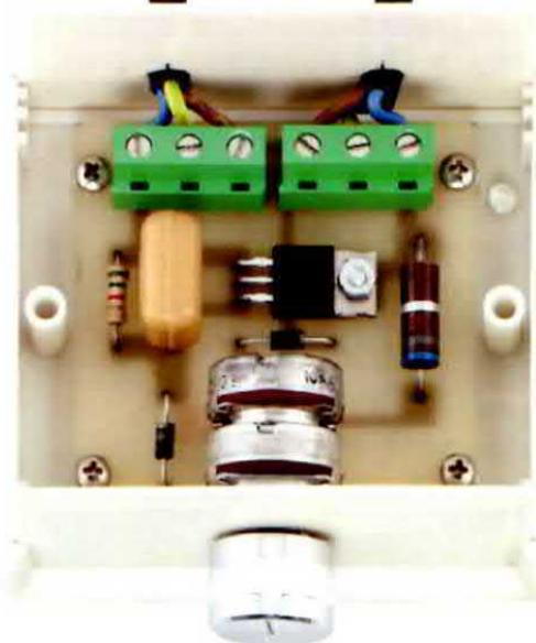
**Fig.4** Il circuito montato di fig.3 va fissato dentro il suo mobile plastico. Sul pannello anteriore fate un foro per far uscire il perno del doppio potenziometro R2, mentre sul pannello posteriore fate un foro per entrare con il filo del cordone di rete ed un secondo foro per uscire con il cordone che andrà ad alimentare il trapano.
