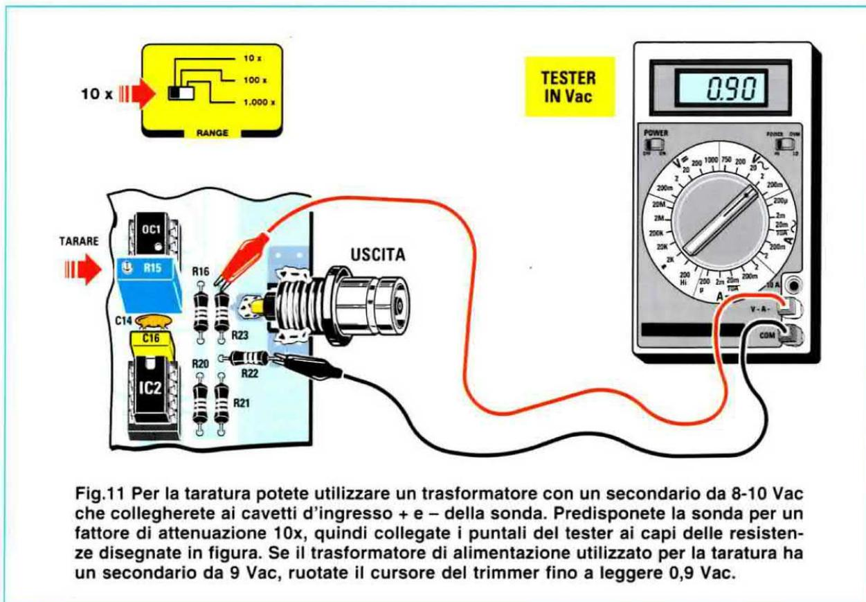
Fig.11 Per la taratura potete utilizzare un trasformatore con un secondario da 8-10 Vac che collegherete ai cavetti d'ingresso + e - della sonda. Predisponete la sonda per un fattore di attenuazione 10x, quindi collegate i puntali del tester ai capi delle resistenze disegnate in figura. Se il trasformatore di alimentazione utilizzato per la taratura ha un secondario da 9 Vac, ruotate il cursore del trimmer fino a leggere 0,9 Vac.
