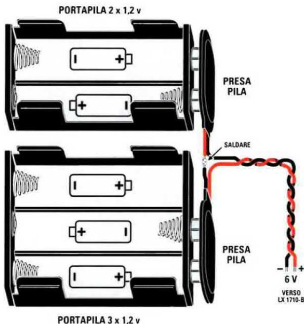
Fig.27 In questo disegno abbiamo raffigurato il collegamento da eseguire tra i due portapile che troverete in dotazione nel kit, che andranno alloggiati nello spazio ad essi riservato all'interno del mobile (vedi foto in alto) e collegati, per mezzo dei due capicorda rosso/nero, alla scheda base siglata LX.1710/B.
