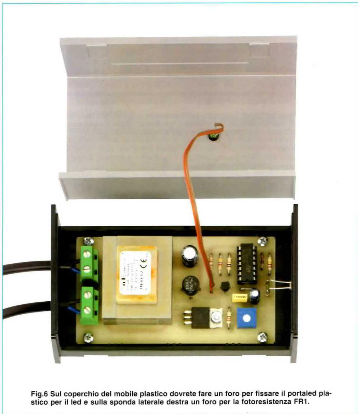
**Fig.6** Sul coperchio del mobile plastico dovrete fare un foro per fissare il portaled plastico per il led e sulla sponda laterale destra un foro per la fotoresistenza FR1.
