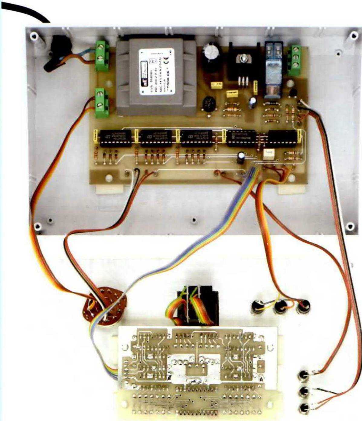
**Fig.11** Foto del Timer montato nel suo mobile. Il circuito stampato base va bloccato con i distanziatori plastici, mentre sul pannello di alluminio dovete fissare il circuito display, i tre pulsanti, i tre diodi led, il commutatore rotativo e i due commutatori bi-nari dopo aver incastrato sui loro lati le due sponde a molla (vedi fig.8).
