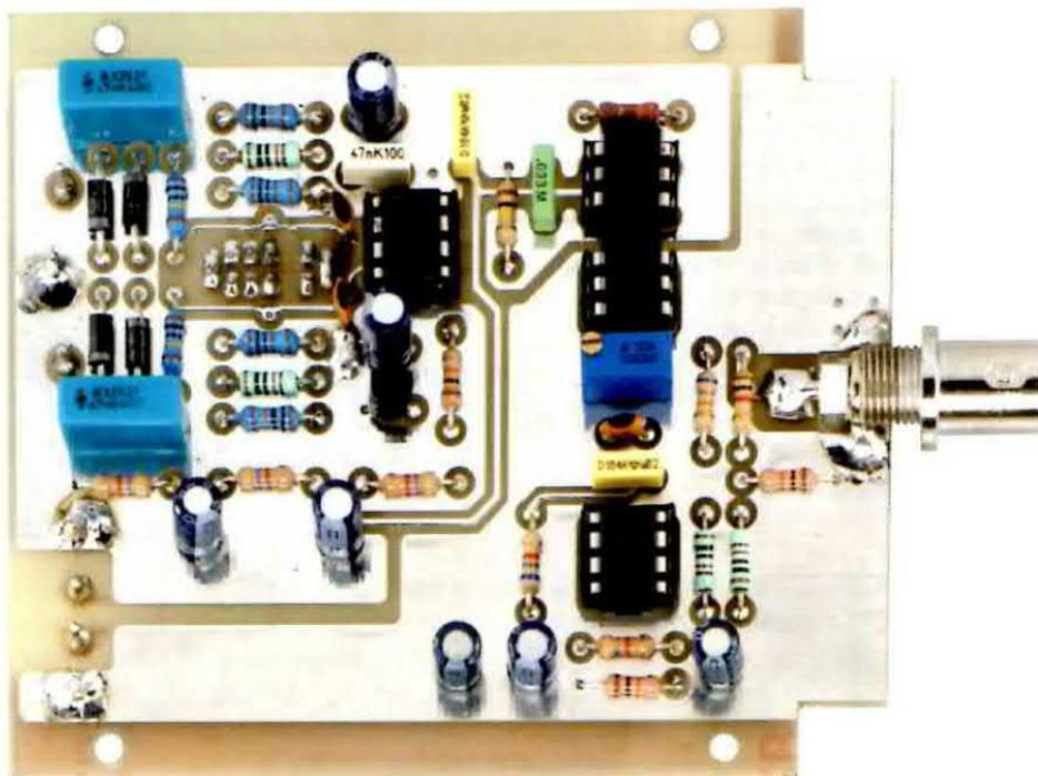
**Fig.4** La sonda LX.1707 ripresa dal lato componenti. Nella foto si vede chiaramente che il connettore BNC di uscita è direttamente saldato sullo stampato e la sua carcassa metallica bloccata con due punti di saldatura alla massa schermata.
