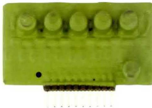
Fig.15 Foto del modulo KM01.60. Ogni modulo contiene due blocchi di amplificazione in classe A pura, senza controreazione interna, indipendenti ed accessibili dall'esterno. Collegando i due blocchi in cascata si ottiene un guadagno di 60 dB.
