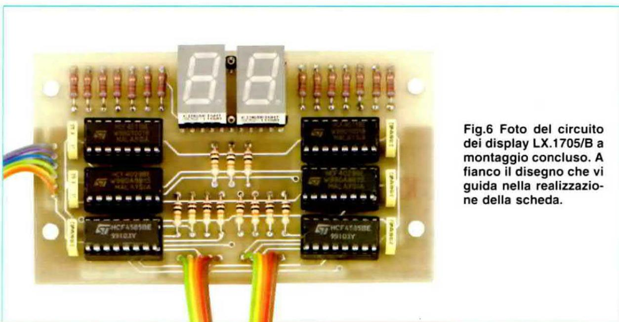
Fig.6 Foto del circuito dei display LX.1705/B a montaggio concluso. A fianco il disegno che vi guida nella realizzazione della scheda.
