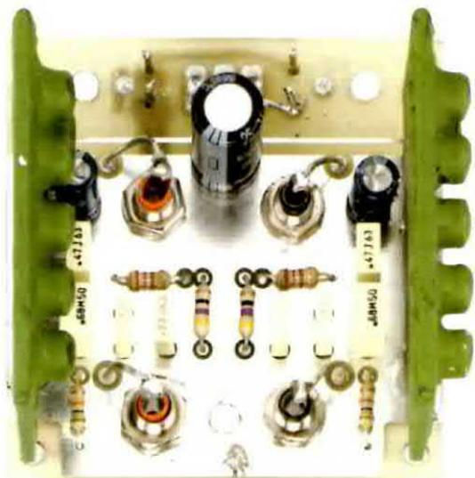
Fig.14 Riproduzione del lato componenti del preamplificatore RIAA a montaggio ultimato. In alto i terminali capicorda ai quali collegherete i fili delle due prese pila.
