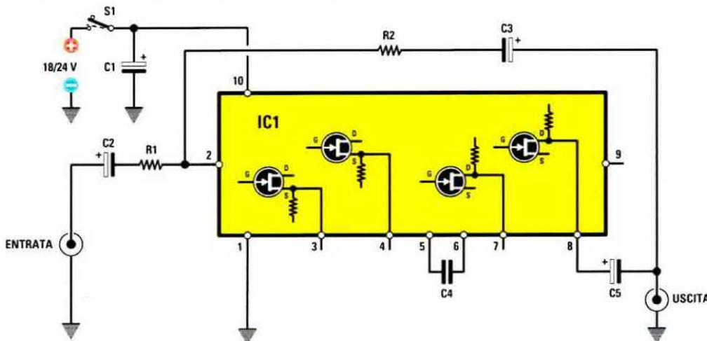
Fig.7 Lo schema teorico con guadagno unitario qui riprodotto può essere equiparato al classico circuito con operazionale in configurazione invertente (vedi disegno in alto). Alla rete di controreazione serve un condensatore da 4,7 microfarad (vedi C3).
