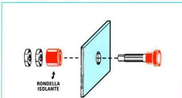
**Fig.9** Sebbene il mobile usato per la sonda sia plastico e quindi non sia necessario isolare le boccole, è buona norma montare questi componenti come disegnato in questo esploso. Sfilate dunque dal corpo della boccola la rondella di plastica per inserirla dalla parte interna del pannello, quindi infilate la boccola e bloccatela con i dadi.
