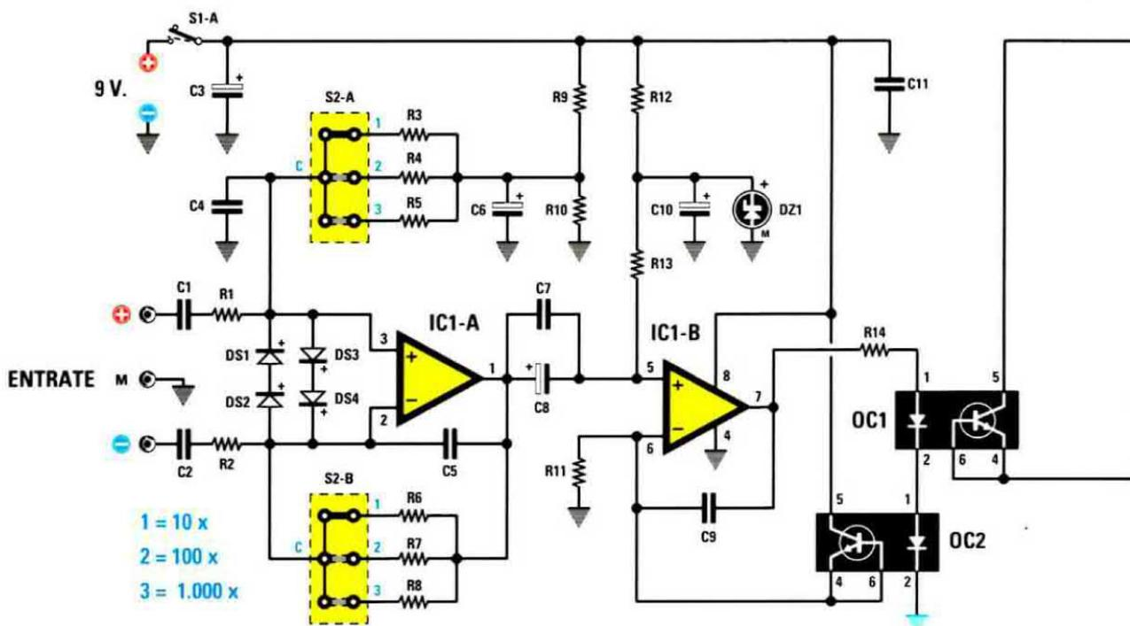
**Fig.6** Schema elettrico della sonda differenziale optoisolata LX.1707. I due stadi del circuito hanno le masse separate, evidenziate nel disegno con i colori nero e blu, e sono alimentati dal deviatore S1/A-S1/B collegato in serie ai poli positivi di due pile a 9 volt. Il deviatore S2/A-S2/B ci consente di attenuare il segnale in ingresso di 10-100 o 1.000 volte, mentre con il trimmer R15 possiamo calibrare l'uscita della sonda.
