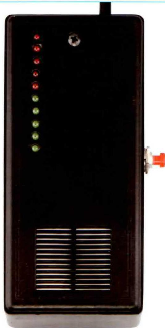
Fig.7 Sul coperchio del mobile plastico c'è un'apertura a griglia. Soffiandoci attraverso, questa permette al fiato di raggiungere la sonda dell'Etilometro. Soffiate energicamente per far uscire l'aria che risulta presente all'interno del mobile.
