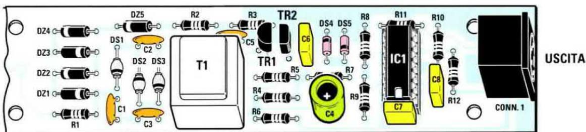
Fig.7 Schema pratico di montaggio della scheda LX.1710/A che andrà collocata all'interno del manipo con il quale eseguirete le vostre rilevazioni. Per il fissaggio del tubo vi raccomandiamo di attenervi alle raccomandazioni riportate nel testo. Il tubo Geiger andrà bloccato mediante quattro gocce di adesivo al silicone, garantendo allo stesso tempo un fissaggio ottimale del tubo e la sua massima esposizione alle radiazioni.
