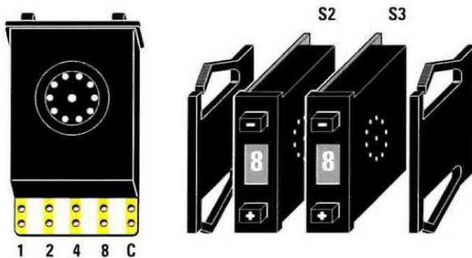
Fig.8 Su lati esterni dei commutatori binari S2-S3 vanno montate le due sponde a "molla", che provvederanno a bloccarli nella fessura sul pannello frontale.
