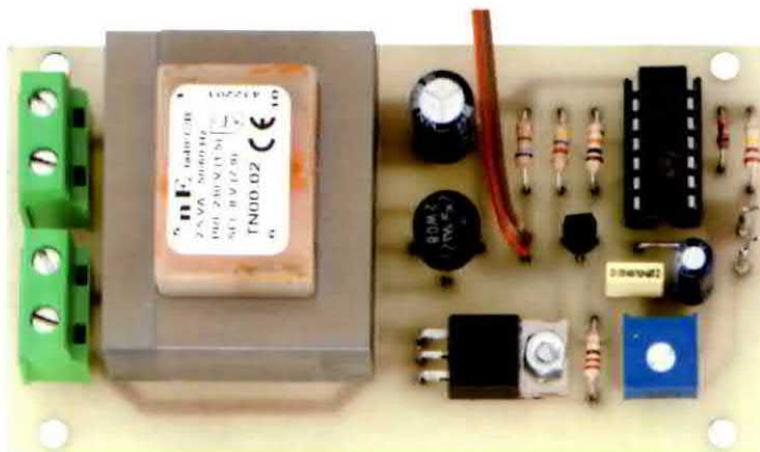
Fig.5 Foto del circuito stampato con tutti i componenti già montati. Sul lato destro si nota la minuscola fotoresistenza FR1. Quando inserite l'integrato IC1 nel suo zoccolo rivolgete la tacca di riferimento ad U verso il basso (vedi fig.4).
