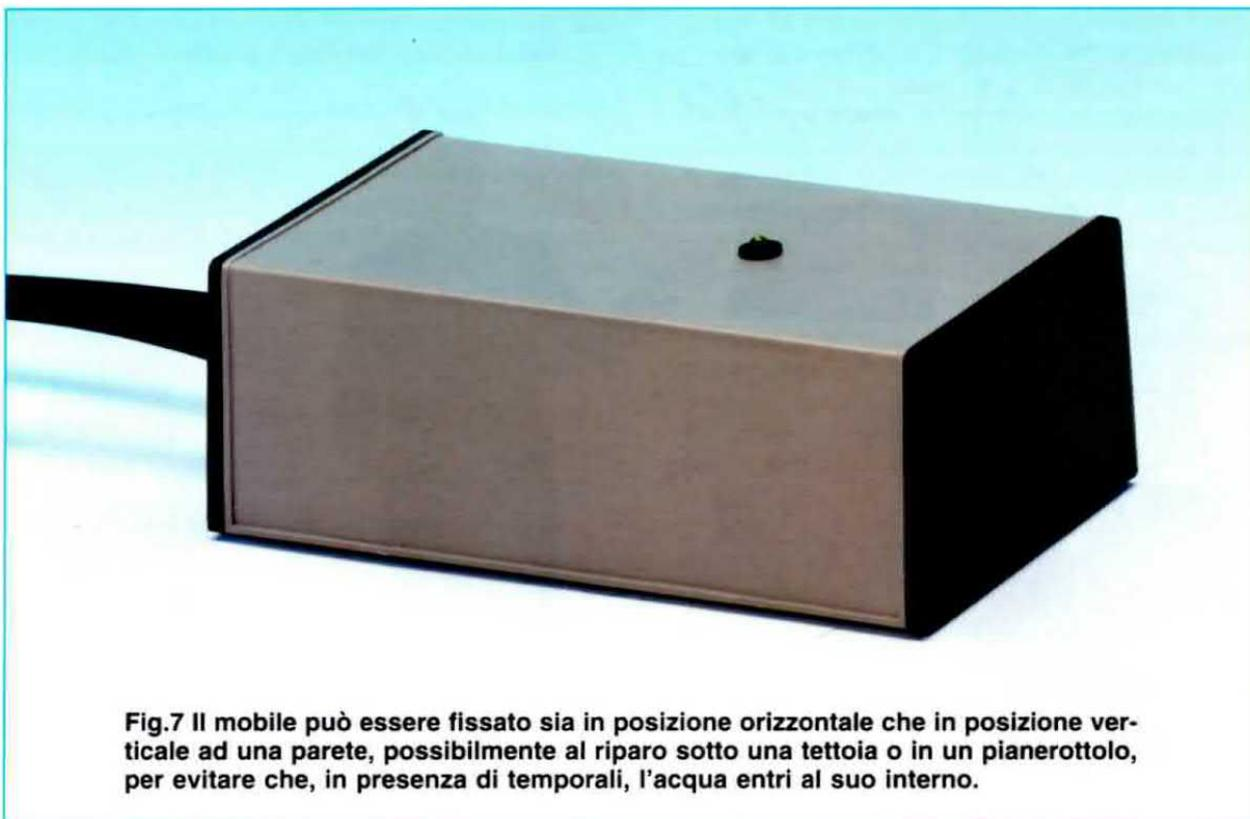
**Fig.7 Il mobile può essere fissato sia in posizione orizzontale che in posizione verticale ad una parete, possibilmente al riparo sotto una tettoia o in un pianerottolo, per evitare che, in presenza di temporali, l'acqua entri al suo interno.**
