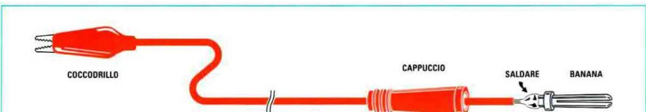
**Fig.10** Nel blister trovate tre spinotti di diverso colore (rosso, nero e giallo) e tre morsetti a cocodrillo completi di filo unipolare per realizzare i tre cavetti d'ingresso della sonda. Preparate ogni filo raschiando una piccola parte della guaina plastica e deponendogli sopra un po' di stagno per assicurare un buon contatto elettrico, quindi fate passare il filo attraverso il cappuccio plastico e saldatelo alla banana.
