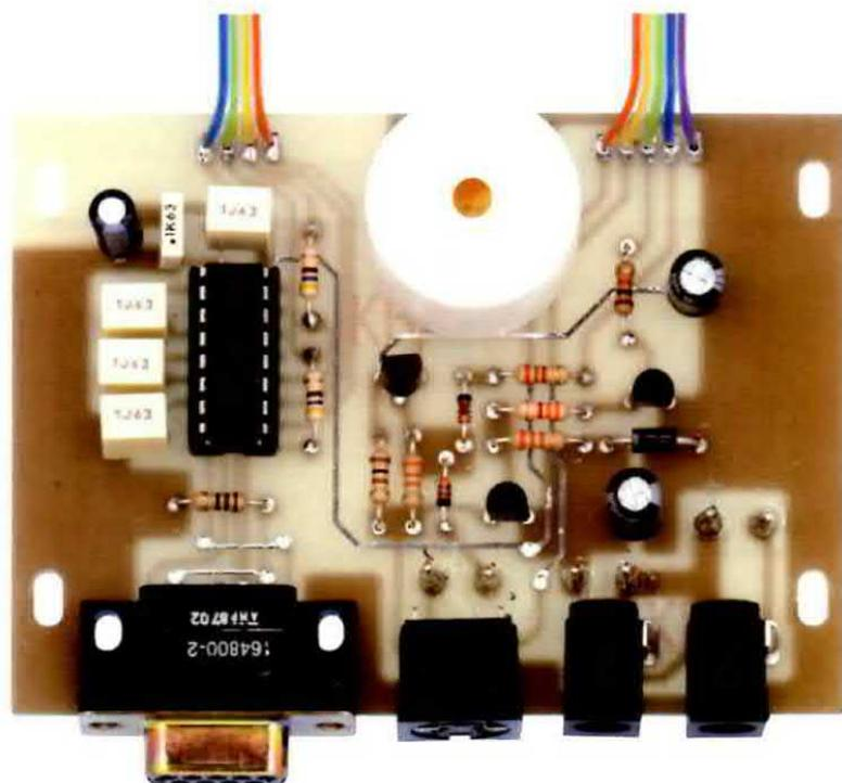
**Fig.16** Foto del circuito base LX.1710/B una volta completato il montaggio. In alto il connettore CONN.D a 4 e 5 terminali con il quale eseguirete il collegamento con la scheda LX.1710/C e in basso i due connettori CONN.3 e CONN.1 e le due prese destinati ai collegamenti esterni.
