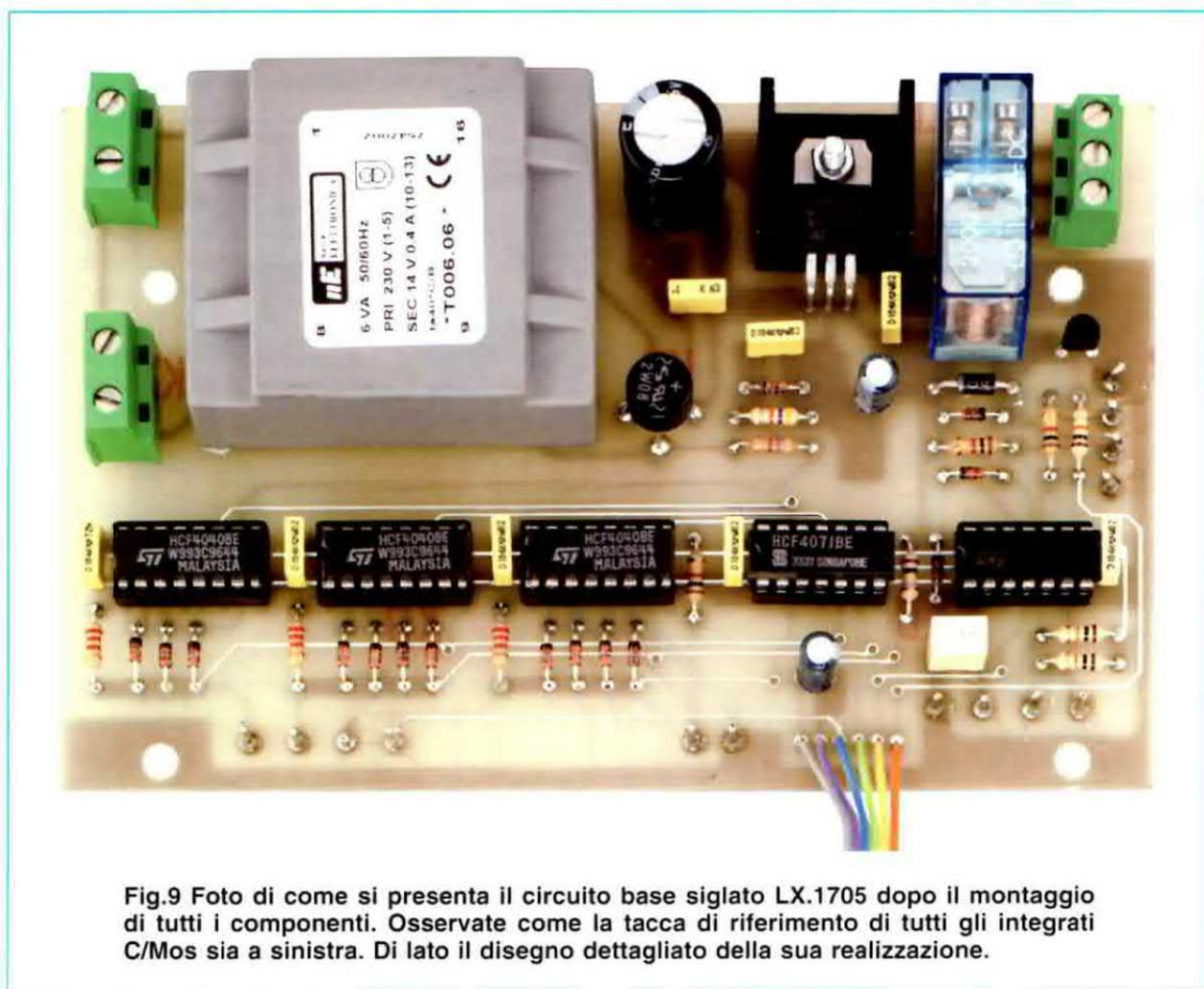
Fig.9 Foto di come si presenta il circuito base siglato LX.1705 dopo il montaggio di tutti i componenti. Osservate come la tacca di riferimento di tutti gli integrati C/Mos sia a sinistra. Di lato il disegno dettagliato della sua realizzazione.
