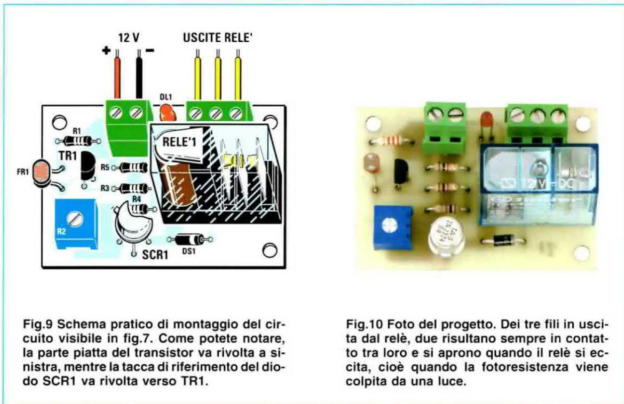
Fig.9 Schema pratico di montaggio del circuito visibile in fig.7. Come potete notare, la parte piatta del transistor va rivolta a sinistra, mentre la tacca di riferimento del diodo SCR1 va rivolta verso TR1.
