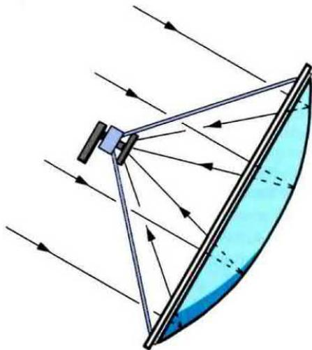
**Fig.5** I gradi di Azimut e di Elevazione della Tabella che abbiamo riportato sulla rivista N.234 risultano validi solo per le parabole a "primo fuoco", cioè quelle di tipo Circolare il cui convertitore LNB risulta posto sul punto focale che si trova al centro della parabola.
