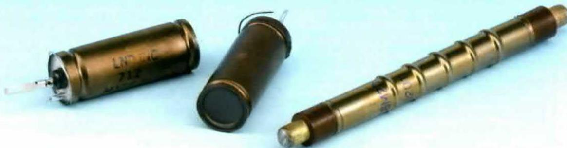
Fig.1 Nel nuovo contatore Geiger abbiamo adottato il tubo LND 712, sensibile alle radiazioni alfa, beta e gamma, dotato di una finestra in mica, di produzione americana, già ampiamente diffuso sulla strumentazione in commercio. Chi vorrà utilizzare il precedente tubo SBM 20, sensibile alle radiazioni beta e gamma, di fabbricazione russa, potrà ancora farlo, perché il contatore è predisposto per alloggiare entrambi i sensori.
