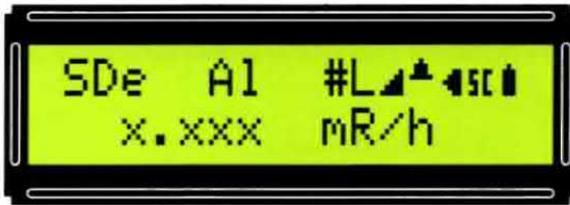
Fig.41 Nel disegno a lato sono rappresentati i simboli e le sigle che potranno comparire sul display durante il funzionamento del contatore Geiger.
