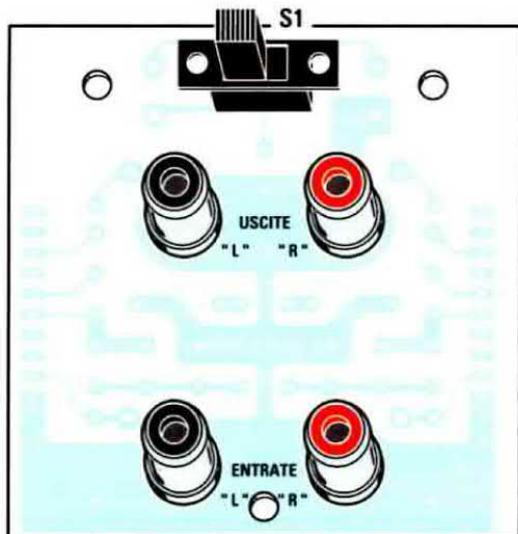
Fig.11 Schema pratico di montaggio del preamplificatore RIAA visto dal lato rame. Iniziate il montaggio da questo lato inserendo il deviatore a slitta e le quattro prese RCA: due per le uscite sinistra-destra (L-R) e due per le entrate sinistra-destra (L-R). Le prese sono saldate sul lato visibile in fig.13 con corti spezzoni di filo d'argento.
