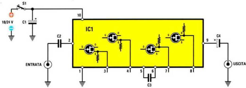
Fig.6 Schema di un amplificatore in classe A pura con il modulo KM01.60. I 60 dB si ottengono collegando in cascata i due blocchi di amplificazione (vedi piedini 5-6).
