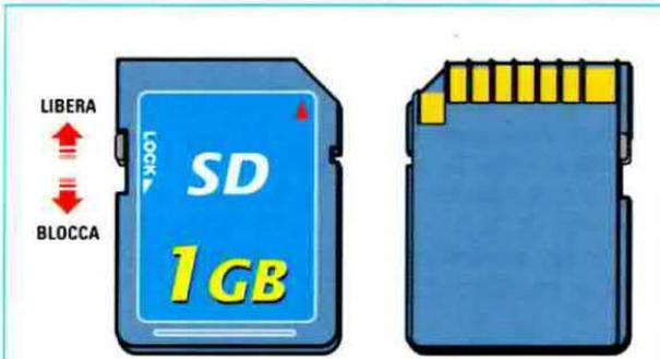
Fig.29 Sul lato sinistro della SD card è presente un piccolo selettore contraddistinto dalla scritta Lock che viene utilizzato per bloccare la card, proteggendola in fase di scrittura e lettura. Durante il normale uso, verificate che il selettore sia posizionato verso l'alto, altrimenti non potrete memorizzare nella card i dati misurati dal contatore. Tenete presente che la SD card va inserita come indicato in figura e cioè con l'angolo smussato rivolto verso sinistra.
