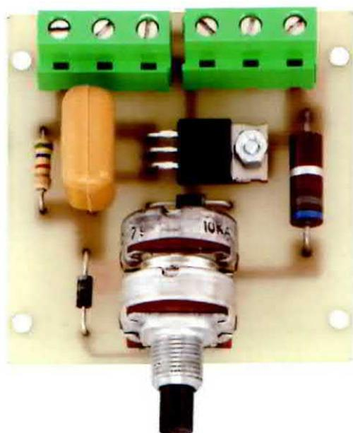
**Fig.3** Foto del circuito a montaggio completato. Per riuscire ad infilare il doppio potenziometro nelle sei fessure del circuito stampato dovete tagliare gli occhielli dei suoi terminali. I tre terminali del diodo SCR vanno ripiegati ad L e, dopo averli saldati, il suo corpo va bloccato al circuito con una vite in ferro ed il suo dado.
