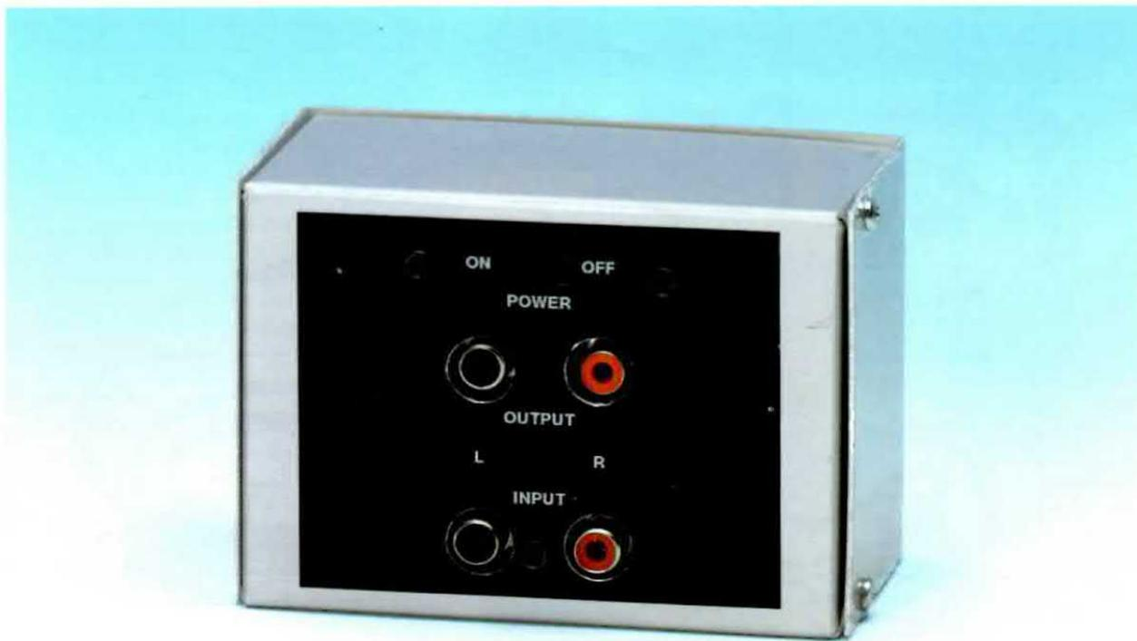
**Fig.17 Foto del preamplificatore RIAA stereo racchiuso dentro il mobile metallico che vi forniamo già forato e con una mascherina adesiva di colore nero.**
