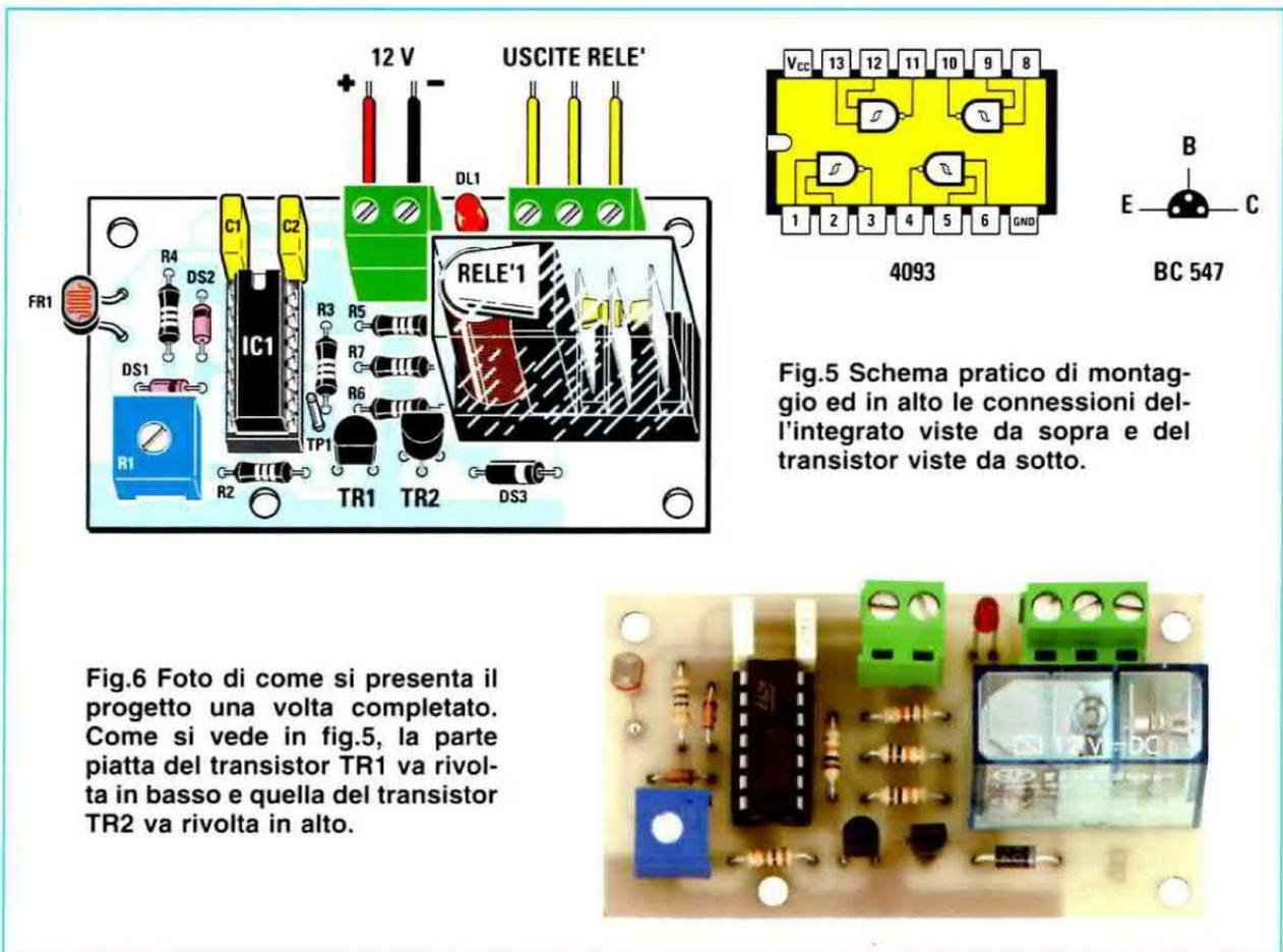
Fig.6 Foto di come si presenta il progetto una volta completato. Come si vede in fig.5, la parte piatta del transistor TR1 va rivolta in basso e quella del transistor TR2 va rivolta in alto.
