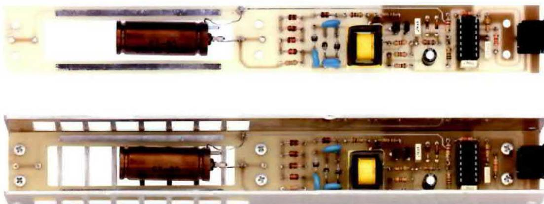
**Fig.15** In queste foto appare riprodotto il circuito stampato LX.1710/A di supporto al tubo Geiger LND 712 a montaggio ultimato e una volta collocato all'interno del supporto metallico. Onde stabilire un perfetto collegamento, vi raccomandiamo di eseguire con cura le saldature tra le due piazzole dello stampato e i terminali del tubo.
