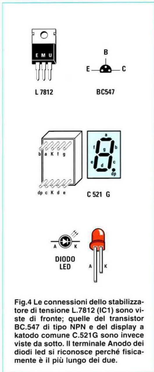
Fig.4 Le connessioni dello stabilizzatore di tensione L.7812 (IC1) sono viste di fronte; quelle del transistor BC.547 di tipo NPN e del display a katodo comune C.521G sono invece viste da sotto. Il terminale Anodo dei diodi led si riconosce perché fisicamente è il più lungo dei due.
