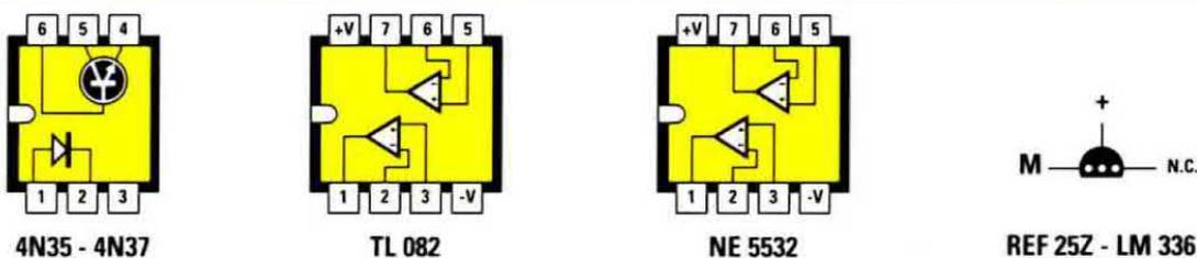
**Fig.5** Connessioni viste da sopra del fotoaccoppiatore 4N35, equivalente al 4N37, usato per trasferire il segnale mantenendo l'isolamento galvanico tra gli stadi del circuito. Anche le connessioni degli integrati TL.082 ed NE.5532 sono viste da sopra, mentre quelle del diodo zener REF.25Z, equivalente all'LM.336, sono viste da sotto.
