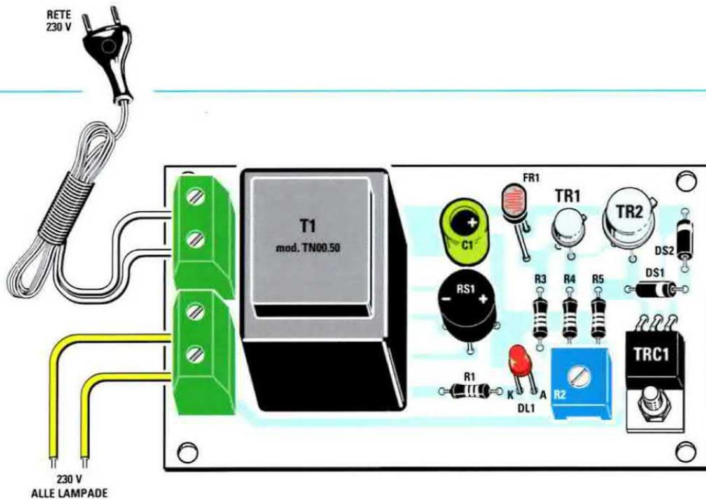
**Fig.16** Schema pratico di montaggio dell'interruttore crepuscolare e foto del circuito montato. Le tacche sporgenti dei transistor metallici vanno rivolte entrambe in alto a destra.
