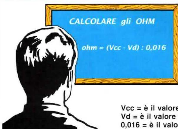
Fig.4 Formula da utilizzare per calcolare il valore in ohm della resistenza di caduta conoscendo i valori Vcc e Vd.
