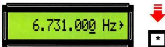
Fig.18 Per variare la frequenza impostata dovete premere sul tasto **\*** e noterete che il primo 0 di destra verrà sottolineato per segnalare che, premendo i tasti **+ o -**, si modificherà questo numero.
