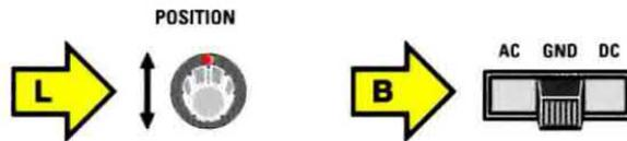
Fig.30 Dopo aver posizionato la levetta del deviatore indicato con la freccia B in posizione GND, ruotate la piccola manopola dello Spostamento traccia in Orizzontale, contrassegnata con la freccia L, fino a portare la traccia dell'oscilloscopio sulla prima riga posta in basso come visibile in questo disegno.
