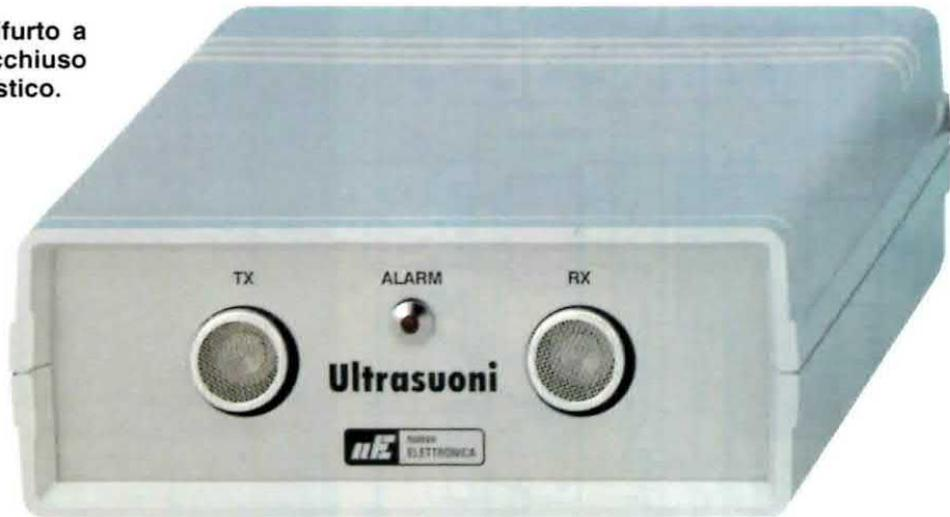
Questo circuito ad Ultrasuoni rileva qualsiasi oggetto in movimento che si trovi entro una distanza di circa 4 metri, quindi lo potrete utilizzare come Antifurto oppure per controllare la qualità assorbente di un materiale acustico che, se efficiente, non riuscirà a riflettere gli Ultrasuoni.
