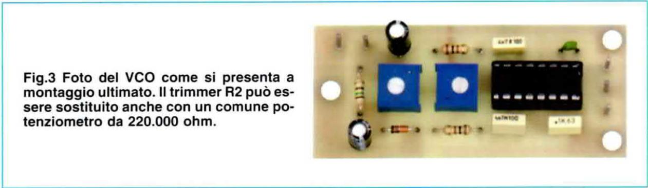
Fig.3 Foto del VCO come si presenta a montaggio ultimato. Il trimmer R2 può essere sostituito anche con un comune potenziometro da 220.000 ohm.
