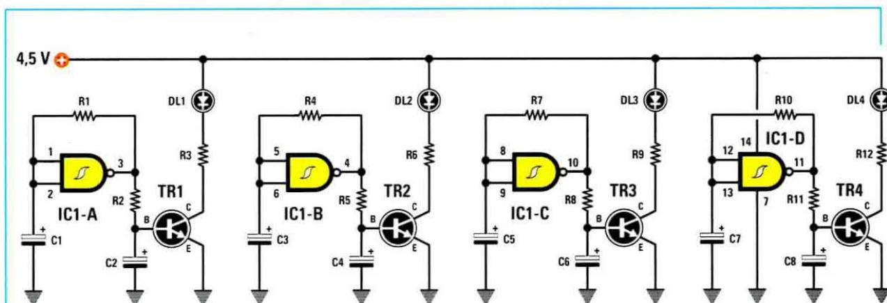
Schema elettrico del lampeggiatore e, sotto, connessioni dell'integrato 4093, del transistor BC337 e del diodo led utilizzati nel circuito.
