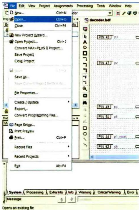
**Fig.17** Per introdurre nuovi componenti, dovette iniziare con il richiamarli: nel caso specifico dovette aprire il file VHDL per convertirlo ed introdurlo nel Top, vale a dire nel disegno principale del vostro progetto.
