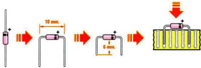
Fig.11 Ora prendete dal kit i 4 diodi DS1-DS2-DS3-DS4. Come sapete la fascia nera stampigliata sul corpo di questo componente indica il **catodo (K)** del diodo, mentre l'altro terminale corrisponde all'**anodo (A)**.
