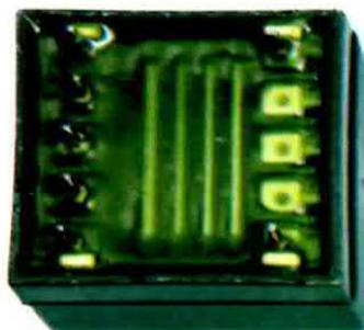
**Fig.7** Il trasformatore T2 non vi viene fornito "nudo" come visibile in fig.6, ma inserito in un contenitore plastico nel quale viene versata a caldo una speciale resina isolante per proteggere gli avvolgimenti dall'umidità. I terminali dei tre avvolgimenti (vedi fig.2) sono predisposti per entrare nei fori già presenti sul circuito stampato.
