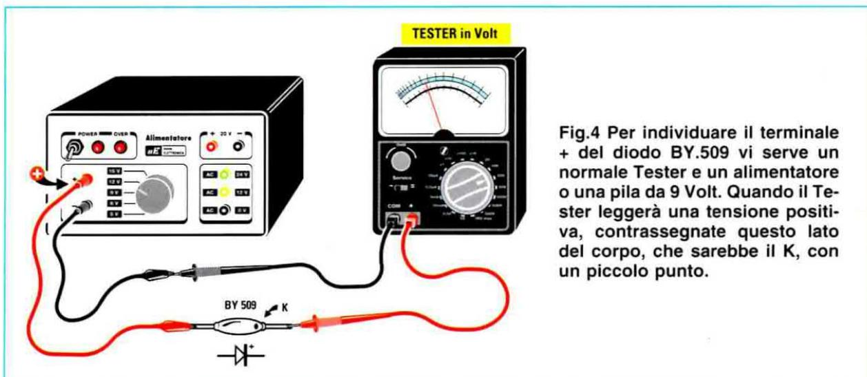
Fig.4 Per individuare il terminale + del diodo BY.509 vi serve un normale Tester e un alimentatore o una pila da 9 Volt. Quando il Tester leggerà una tensione positiva, contrassegnate questo lato del corpo, che sarebbe il K, con un piccolo punto.
