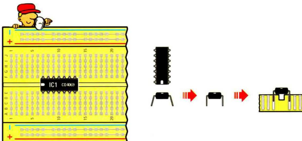
Fig.8 Per iniziare inserite l'integrato **CD4069**, siglato **IC1**, che andrà collocato nei fori a cavallo della striscia **centrale**, nella posizione indicata in figura, e con la tacca di riferimento rivolta **verso sinistra**.
