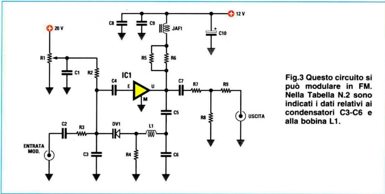
Fig.3 Questo circuito si può modulare in FM. Nella Tabella N.2 sono indicati i dati relativi ai condensatori C3-C6 e alla bobina L1.
