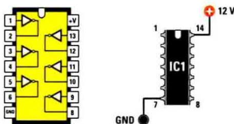
Schema a blocchi dell'integrato CD4069 visto dall'alto con indicazione dei piedini di alimentazione
