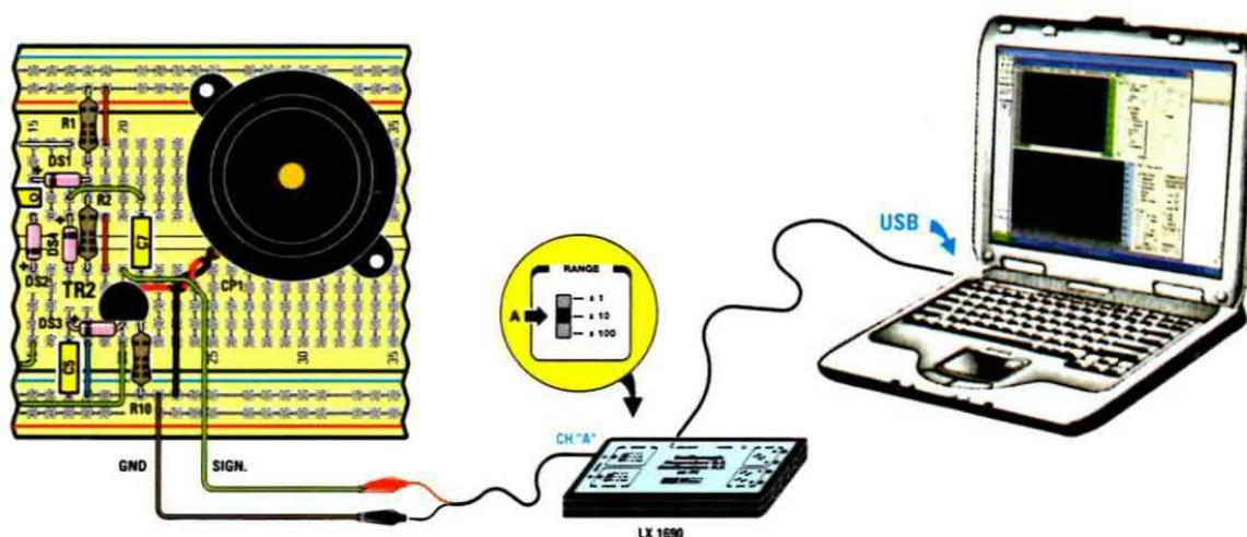
Fig.17 Dopo avere eseguito la calibrazione dell'oscilloscopio dovrete provvedere a collegare al canale **CHA** della scheda **LX.1690** il circuito che avete costruito, come indicato in figura, utilizzando l'apposito **cavetto** munito di connettore **BNC** da un lato e di **due coccodrilli** dall'altro.
