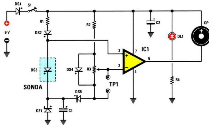
Schema elettrico del circuito e, sotto, connessioni dell'integrato uA.741 viste da sopra e con la tacca di riferimento orientata verso l'alto e del diodo led. Come potete notare, il terminale Anodo è riconoscibile per la maggiore lunghezza.
