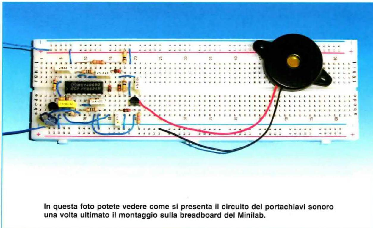
In questa foto potete vedere come si presenta il circuito del portachiavi sonoro una volta ultimato il montaggio sulla breadboard del Minilab.
