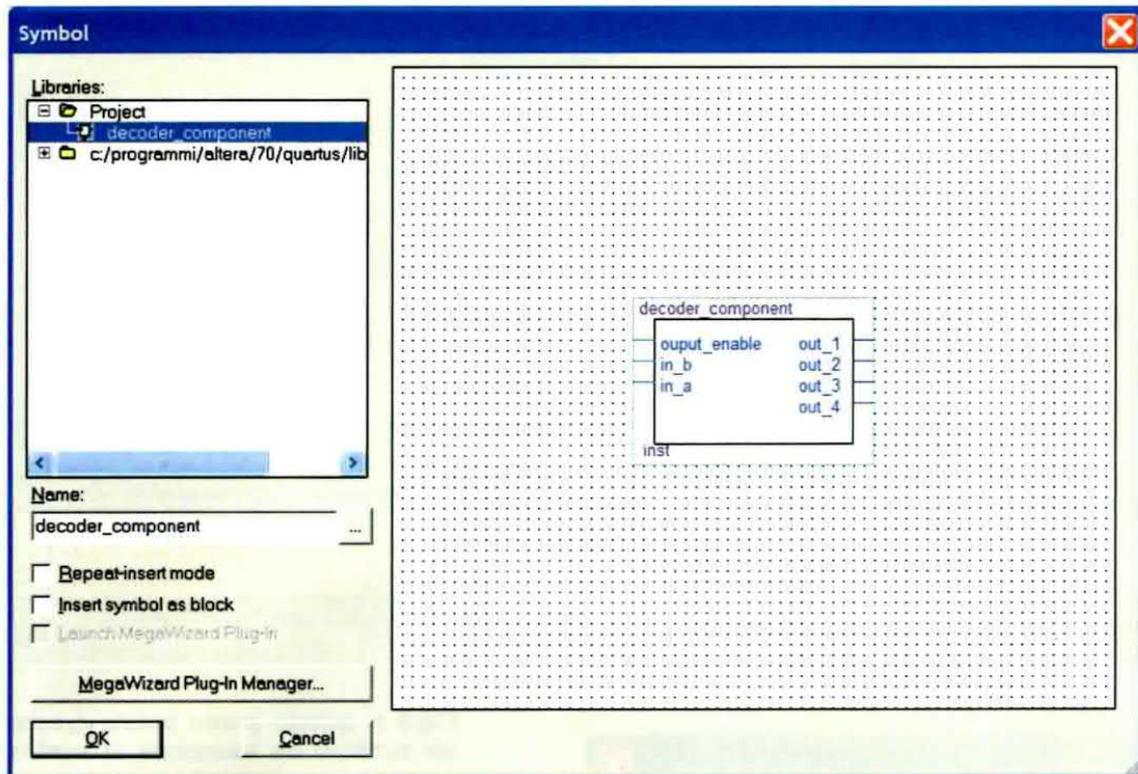
**Fig.11** Seguendo le indicazioni riportate nel testo potete visualizzare il componente creato: come potete notare, oltre ai due ingressi, ne è presente un terzo che rappresenta l'abilitazione in uscita del codice decodificato.
