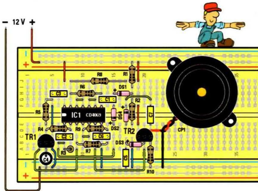
Fig.14 Da ultimo non vi resta che eseguire i collegamenti necessari per l'**alimentazione a 12 Volt** del circuito. Inserite nella breadboard i **due fili** che serviranno per il collegamento all'**alimentatore del Minilab**, facendo molta attenzione a **non invertire** i colori dei due fili **rosso e marrone** collegati rispettivamente alla riga **rossa (+)** e alla riga **azzurra (-)** della basetta.
