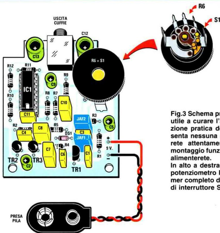
Fig.3 Schema pratico del Generatore utile a curare l'acufene. La realizzazione pratica del progetto non presenta nessuna difficoltà e se seguirete attentamente le istruzioni di montaggio funzionerà non appena lo alimenterete.
