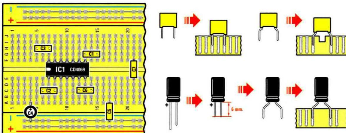
Fig.9 Ora prelevate dal kit i **6 condensatori poliestere C1-C2-C3-C5-C6-C7**. Come già sapete, i condensatori **poliestere** hanno la caratteristica di **non avere polarità**, perciò i loro piedini possono essere **scambiati** tranquillamente tra loro.
