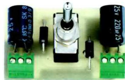
**Fig.3** Foto del circuito stampato come si presenta a montaggio ultimato. Come potete vedere in fig.4, il circuito stampato andrà fissato nel contenitore plastico tramite il dado del deviatore S1.
