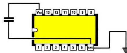
Fig.5 Per disaccoppiare in modo perfetto un integrato affinché scarichi a massa il rumore da esso stesso generato, il condensatore da 100.000 pF va collegato direttamente tra il piedino Vcc e il piedino GND.
