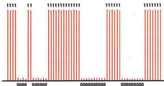
Fig.3 In una trasmissione Digitale il segnale di un'immagine viene scomposto in livelli logici 1-0. Il Decoder provvede a convertire un segnale digitale in un segnale analogico. Un Decoder può essere paragonato ad un lettore di Codici a Barre del tipo utilizzato per leggere nelle etichette i dati relativi ad un determinato prodotto.
