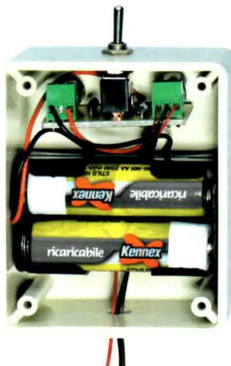
Fig.5 Foto del contenitore aperto come si presenta a montaggio ultimato.
