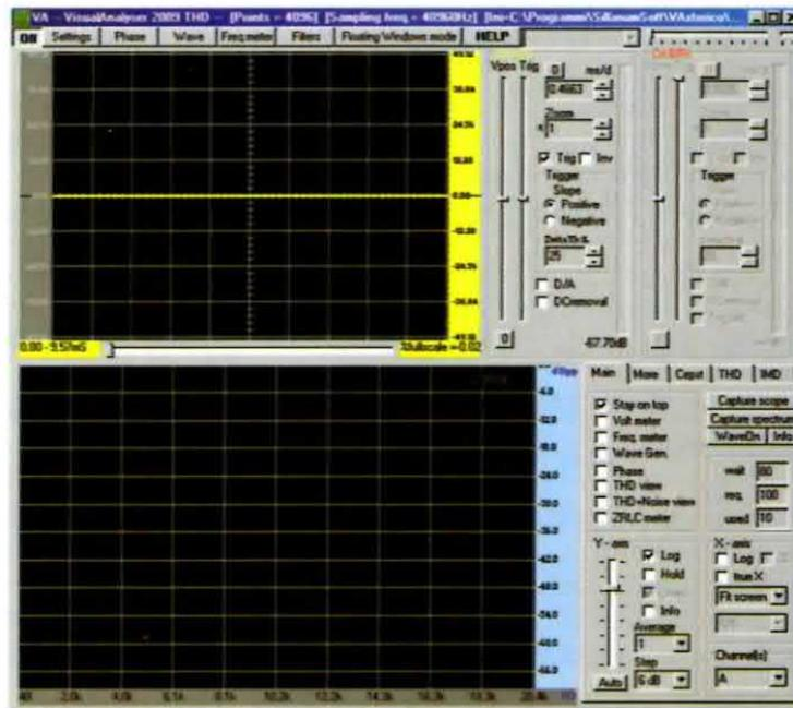
Fig.19 La **finestra principale** del VA che compare sul computer è composta da due schermi. Lo schermo superiore è lo schermo dell'**oscilloscopio**, che utilizzeremo per osservare i diversi segnali presenti sul nostro circuito.
