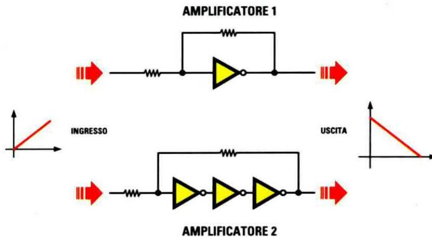
Fig.2 Nella configurazione **amplificatore**, che abbiamo rappresentato nella figura riprodotta in alto, il circuito ha la caratteristica di amplificare una tensione che varia con **continuità** al suo ingresso. Per trasformare l'inverter in un **amplificatore** occorre inserire una resistenza in serie all'ingresso e collegare poi l'uscita al suo ingresso tramite una seconda **resistenza** (vedi **amplificatore 1**).
