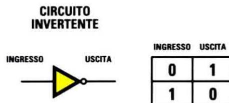
Fig.3 Nella configurazione **circuito invertente**, invece, visibile qui sopra, il circuito lavora con **due soli livelli di tensione**, che corrispondono ad uno **0 logico** e ad un **1 logico**.
