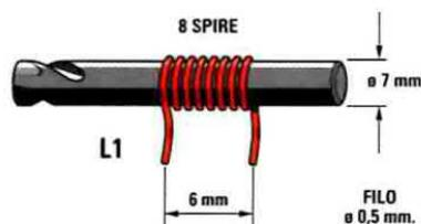
**Fig.4** Per realizzare la bobina L1 prendete del filo di rame smaltato da 0,5 mm ed avvolgete intorno ad una punta di trapano del diametro richiesto il numero di spire necessario. Le spire andranno avvolte affiancate e poi spaziate fino ad ottenere la lunghezza richiesta. Le due estremità della bobina andranno raschiate per asportare lo strato di smalto che le riveste, poi su questo filo nudo andrà depositato un sottile strato di stagno.
