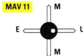
Fig.1 In questo disegno vi presentiamo il MAV.11 ingrandito ben 4 volte. Sul suo corpo è presente un piccolo punto bianco in corrispondenza del terminale d'Uscita. Dal lato opposto è presente il terminale Entrata e gli altri due terminali indicati M da collegare a Massa.
