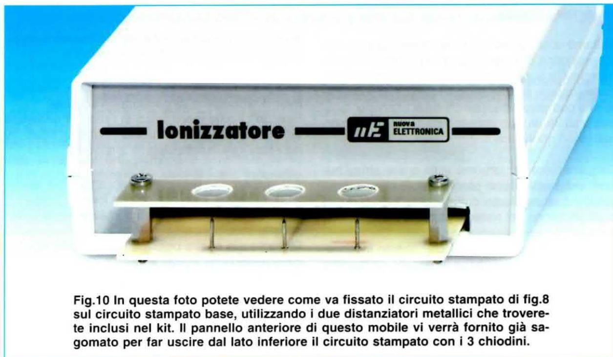
Fig.10 In questa foto potete vedere come va fissato il circuito stampato di fig.8 sul circuito stampato base, utilizzando i due distanziatori metallici che troverete inclusi nel kit. Il pannello anteriore di questo mobile vi verrà fornito già sagomato per far uscire dal lato inferiore il circuito stampato con i 3 chiodini.
