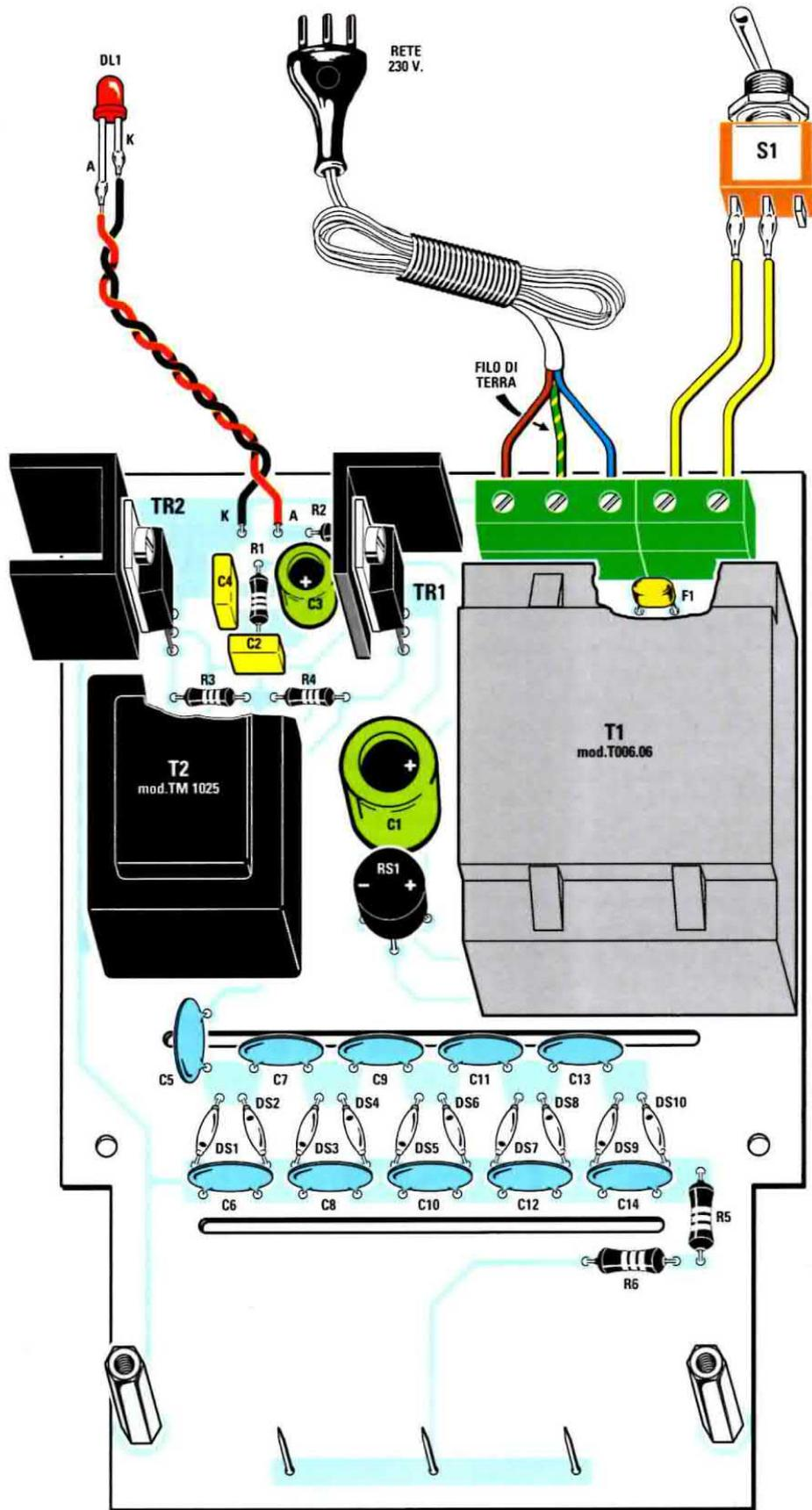
Per saldare i terminali dei **diodi** e dei **condensatori** utilizzate dello stagno di ottima qualità che non lascia sul circuito stampato depositi **gommosi**, diversamente l'alta tensione potrà scaricarsi tra le piste (vedi 1° volume **Imparare l'Elettronica partendo da zero** a pag.70).
