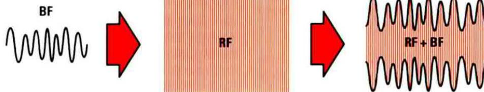
Fig.1 Per ottenere un segnale Analogico si preleva un segnale BF da una telecamera e lo si sovrappone ad un segnale RF, cioè di Alta Frequenza, che esplica la funzione di portante. Nell'etere viaggia quindi un segnale RF modulato da una BF.
