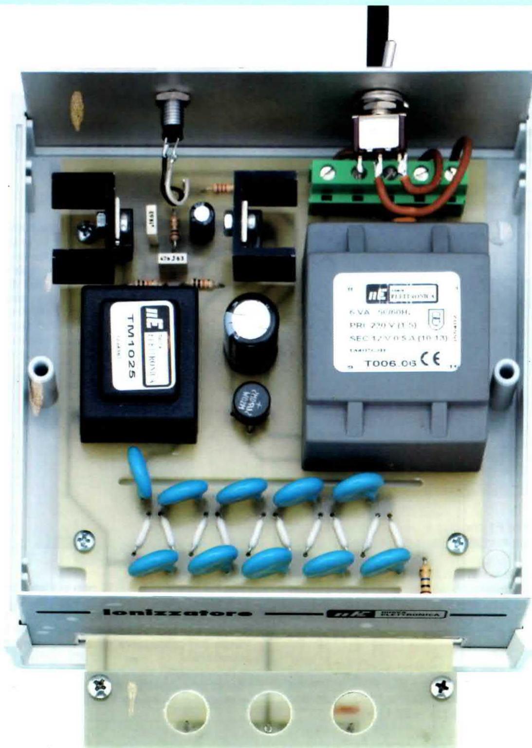
Fig.9 Il circuito stampato LX.1736 con sopra già montati tutti i componenti andrà fissato all'interno del mobile plastico. Sul pannello posteriore dovreste praticare tre fori per applicare il diodo led, il deviatore S1 e per far uscire il cordone di alimentazione (vedi fig.5). Quando fisserete i tre chiodini irradianti sulla parte anteriore dei circuito stampato, collocateli alla stessa altezza, diversamente non vedrete un "puntino luminoso" su tutte le 3 punte, ma su 1 sola punta.
