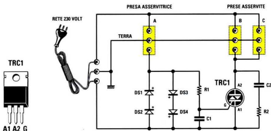
Qui sopra lo schema elettrico utilizzato per spegnere automaticamente le apparecchiature collegate alle prese B-C quando viene spenta l'apparecchiatura collegata alla presa A. Sulla sinistra le connessioni, viste frontalmente, del diodo Triac utilizzato in questo progetto.
