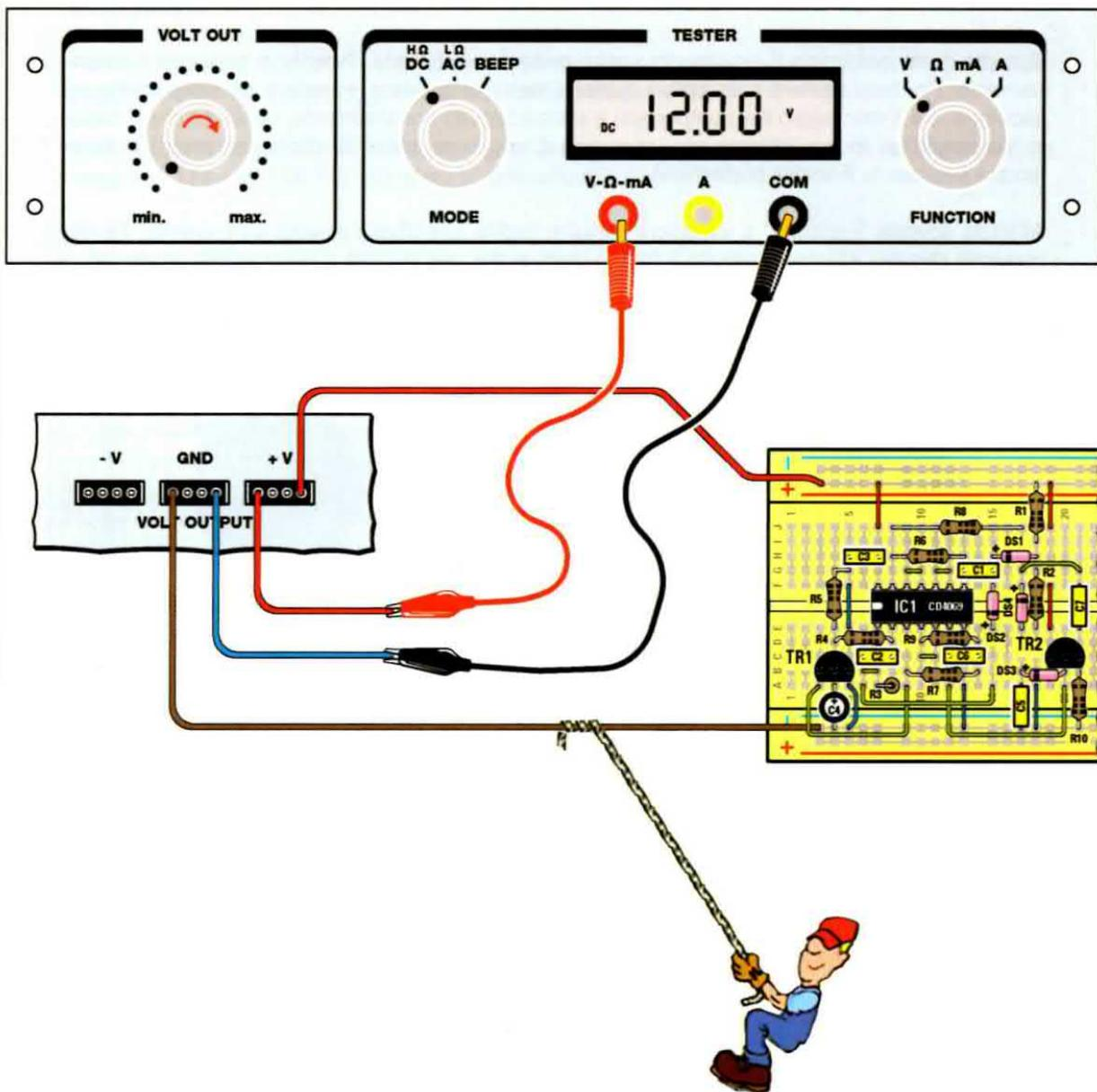
Fig.16 Ora accendete il Minilab. Ruotate piano la manopola **VOLT OUT** in senso **orario** fin quando non leggerete sul **display** del **tester** un valore il più possibile vicino a **12,00**.
