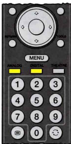
Fig.16 Per sapere se il vostro televisore è già dotato di Decoder digitale, basta verificare se sul Telecomando sono presenti i tasti **ANALOG** e **DIGITAL**.
