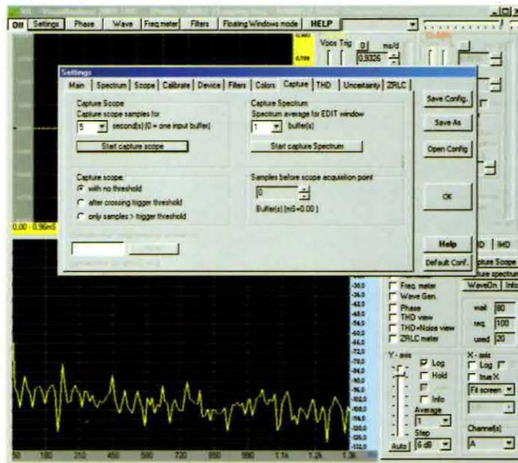
Fig.25 In questa finestra sono presenti due sezioni principali e cioè il **Capture Scope** a sinistra e il **Capture Spectrum** a destra. Noi utilizzeremo la sezione **Capture Scope** che è quella che si riferisce all'**oscilloscopio**.
