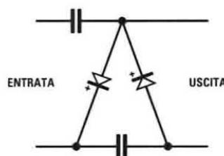
**Fig.1** Uno stadio raddrizzatore-duplicatore di tensione è composto da due diodi e due condensatori. Poichè nel nostro circuito di fig.2 sono presenti **5 stadi duplicatori**, sulla sua uscita otterremo più di **9.000 Volt**.
