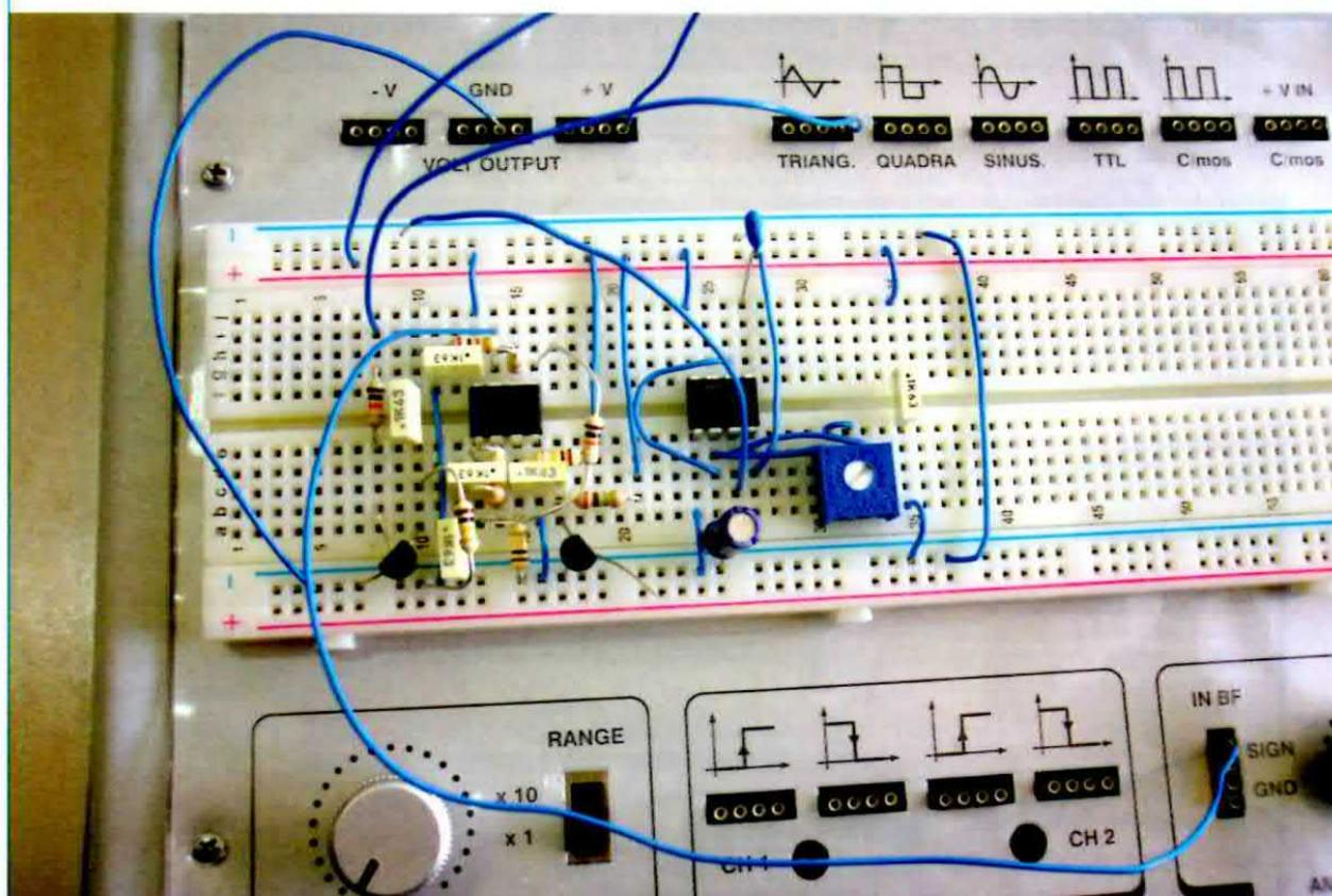
A titolo di curiosità abbiamo voluto sostituire il Generatore ad onda quadra presente sul circuito inviato dal nostro lettore, con il Generatore ad onda triangolare del Minilab. Il suono che abbiamo ottenuto risulta ancora più somigliante a quello di una vera locomotiva a vapore.
