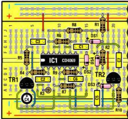
Fig.13 Ora, per completare il circuito, eseguite i collegamenti indicati in figura, facendo molta attenzione a spellare bene il filo, inserendolo poi a fondo nei fori della breadboard, in modo da realizzare un **contatto sicuro**. Come sempre, vi raccomandiamo di curare particolarmente questo punto perché diversamente il vostro circuito non potrà funzionare a dovere.
