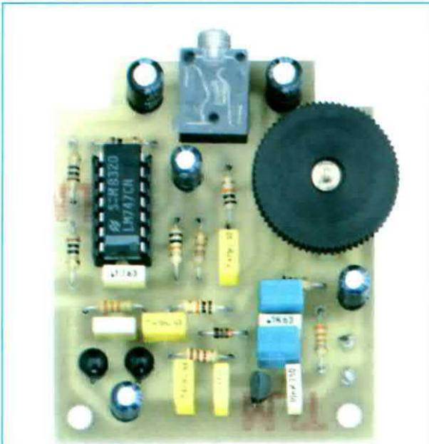
Fig.4 Foto del circuito con sopra già montati tutti i componenti.
