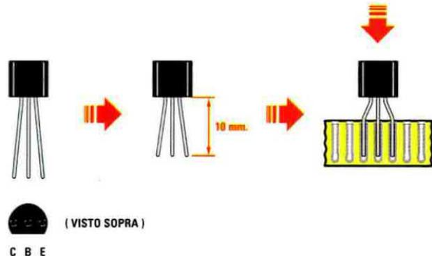
Fig.12 E' ora la volta dei **due transistor BC547** siglati TR1 e TR2. I transistor sono provvisti di tre terminali che corrispondono alla **base (B)**, all'**emettitore (E)** e al **collettore (C)**, come visibile in figura.
