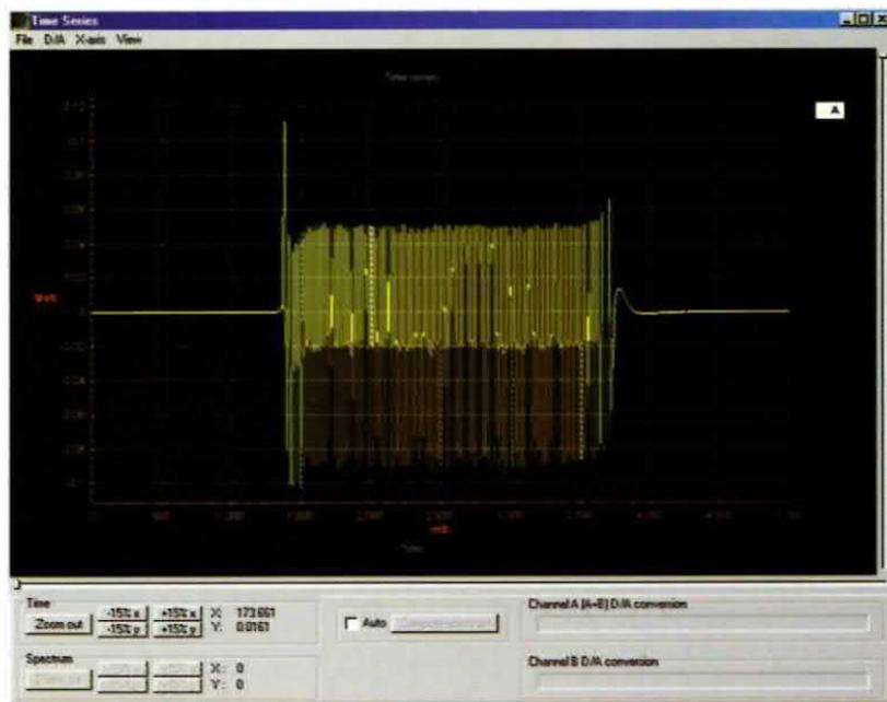
Fig.28 Come potete vedere il **Capture Scope** ha funzionato egregiamente perché è riuscito a fotografare esattamente il punto di partenza dell'oscillatore, mostrandovi come varia il segnale all'uscita dell'oscillatore passando dalla condizione di **riposo** a quella di **attivazione** con il fischio.
