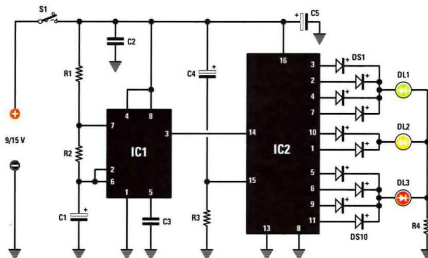
Schema elettrico del semaforo. Poichè il diodo led Verde e il diodo led Rosso devono rimanere accesi per un tempo maggiore rispetto al diodo led Giallo, quest'ultimo viene collegato tramite due diodi al silicio ai piedini 10-1 dell'integrato IC2. Le connessioni degli integrati sono viste da sopra e con la tacca a U rivolta verso sinistra.
