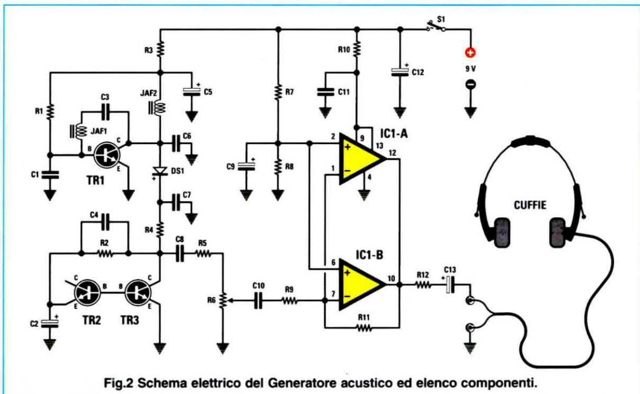
Fig.2 Schema elettrico del Generatore acustico ed elenco componenti.
