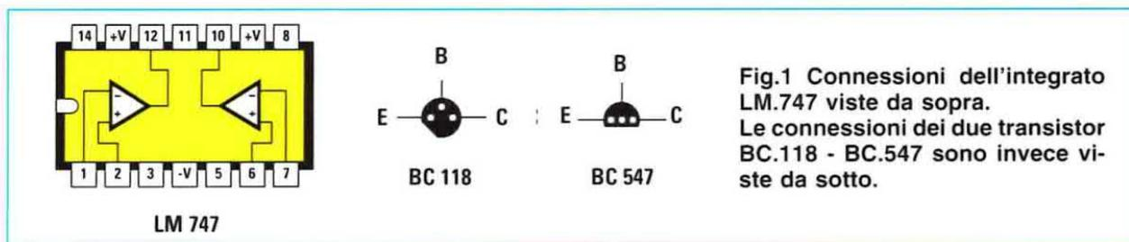
Fig.1 Connessioni dell'integrato LM.747 viste da sopra. Le connessioni dei due transistor BC.118 - BC.547 sono invece viste da sotto.
