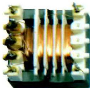
**Fig.6** Il trasformatore T2 siglato TM.1025 ha un nucleo in ferrite perchè viene fatto lavorare sui 50.000 Hz circa. Come risulta ben visibile in questa foto, il suo secondario viene avvolto su un rocchetto provvisto di diversi separatori per evitare che l'alta tensione generata, che si aggira intorno ai 700 Volt, possa scaricarsi tra spira e spira. Questa tensione applicata a 5 celle raddrizzatrici/duplicatrici permetterà di ottenere una tensione di circa 9.800 Volt.
