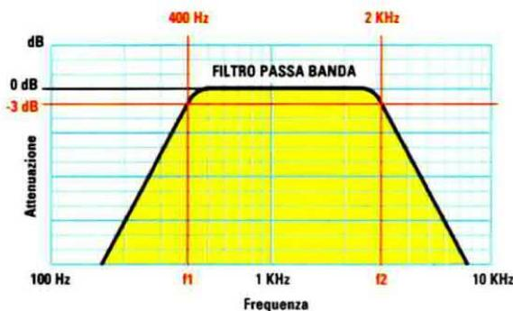
Fig.28 Questo significa che il filtro attenuerà, cioè non lascerà passare, tutte le frequenze che risultano **inferiori a 400 Hz**. Un segnale di frequenza uguale alla **f1**, cioè a **400 Hz**, verrà attenuato invece esattamente di **-3 dB**. Da questo valore di frequenza in su non vi sarà più alcuna attenuazione del segnale (**0 dB**) fino al raggiungimento della frequenza **f2** di **2.000 Hz**.
