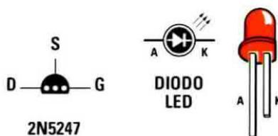
Fig.4 Connessioni viste da sopra dell'LM.747, mentre le connessioni del Fet sono viste da sotto. Il terminale più lungo del diodo led è l'Anodo.
