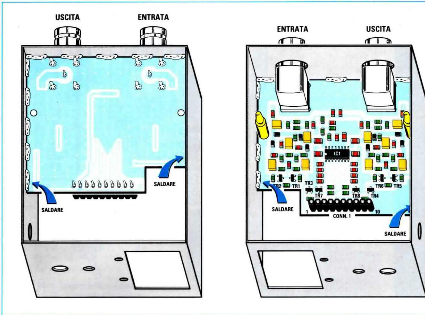
**Fig.10** Come abbiamo evidenziato nei due disegni riprodotti qui sopra, è di fondamentale importanza eseguire un'accurata saldatura della scheda in SMD KM1745K sui bordi del contenitore per ottenere la sua perfetta schermatura.
