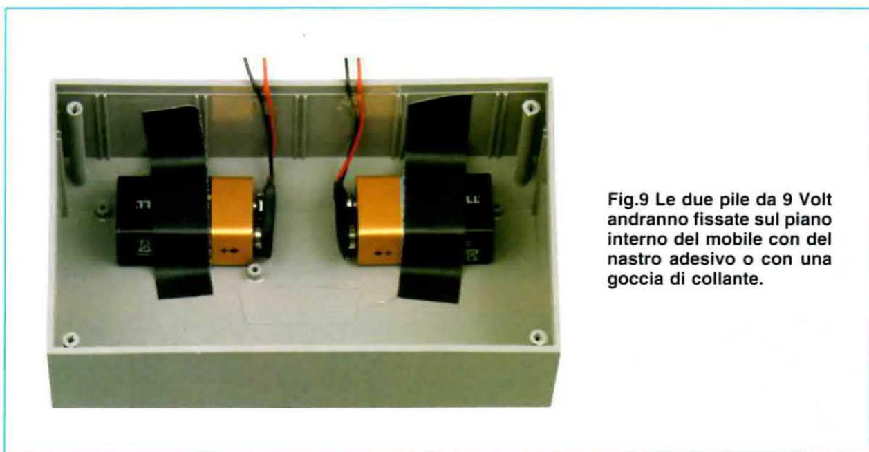
**Fig.9** Le due pile da 9 Volt andranno fissate sul piano interno del mobile con del nastro adesivo o con una goccia di collante.
