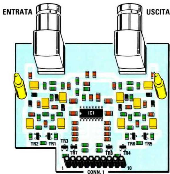
Fig.5 Schema pratico della sezione RF di questo attenuatore siglata KM1745K, che vi forniamo già assemblata con componenti in SMD.
