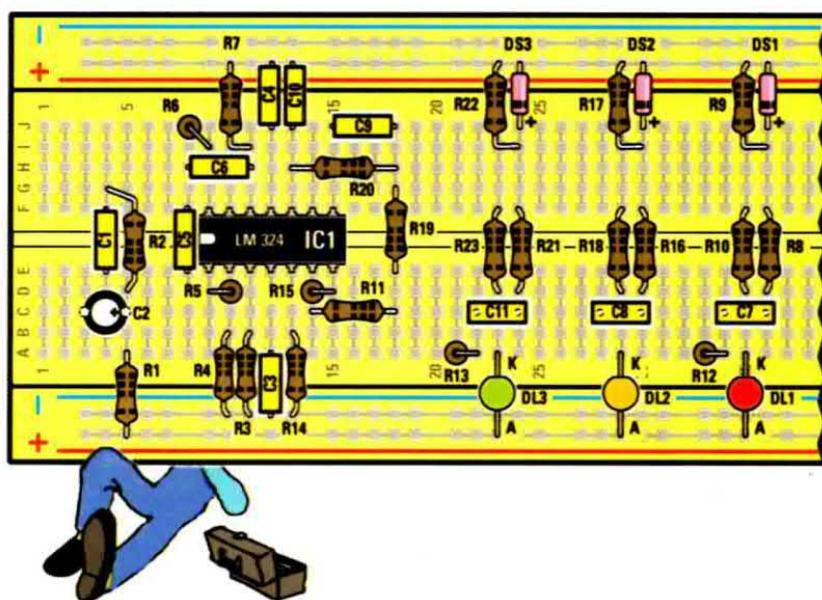
Fig.13 Prelevate ora dal kit i **3 diodi DS1-DS2-DS3**. Se li osservate vedrete che sul corpo di ciascun diodo è stampigliata una **fascia nera** che indica il **catodo (K)**, mentre l'altro terminale corrisponde all'**anodo (A)**. Inserite i diodi nelle posizioni indicate in figura, avendo cura di rivolgere la loro **fascia nera** verso il **basso**.
