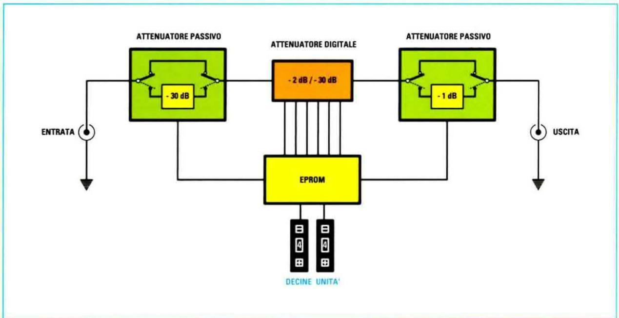
**Fig.2 Schema a blocchi del nostro attenuatore digitale. A sua integrazione abbiamo aggiunto due stadi,  $-1$  dB e  $-30$  dB, per generare valori intermedi. La E-prom viene letta da un selettore che permette di attivare le 8 uscite per i vari valori di attenuazione da  $-1$  a  $-60$  dB.**
