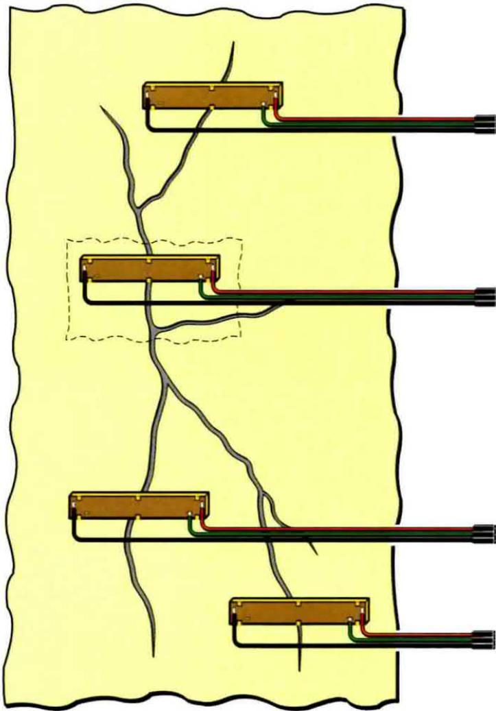
**Fig.14** Per i nostri rilevamenti abbiamo utilizzato dei sensori realizzati con dei semplici slider.
