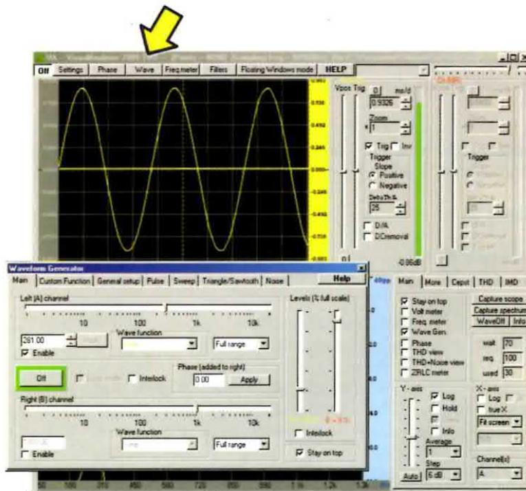
Fig.46 Se volete potete misurare l'ampiezza in **Volt** dell'onda sinusoidale e per farlo basterà cliccare con il tasto sinistro del mouse su uno dei picchi superiori e poi trascinare il mouse fino a fare coincidere la linea orizzontale che si apre con uno dei picchi inferiori della sinusoide.
