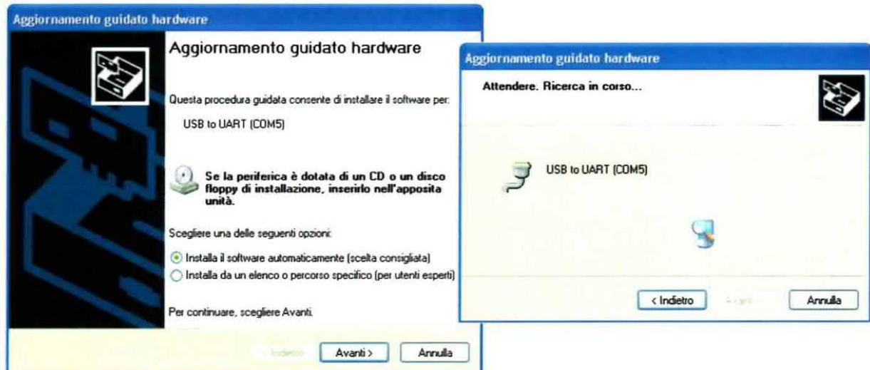
Fig.17 Inserite il cavo USB collegato alla scheda LX.1741 in una presa USB del pc. Il pc riconosce automaticamente una periferica nuova e chiede di installare i Driver. Cliccate in seguito su Avanti, Select, sulla cartella Driver CCS e su Ok. Inizierà una ricerca automatica (vedi finestra a destra) che si concluderà con un messaggio di fine installazione che vi informa che l'operazione ha avuto esito positivo.
