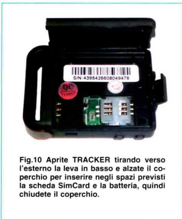
Fig.10 Aprite TRACKER tirando verso l'esterno la leva in basso e alzate il coperchio per inserire negli spazi previsti la scheda SimCard e la batteria, quindi chiudete il coperchio.
