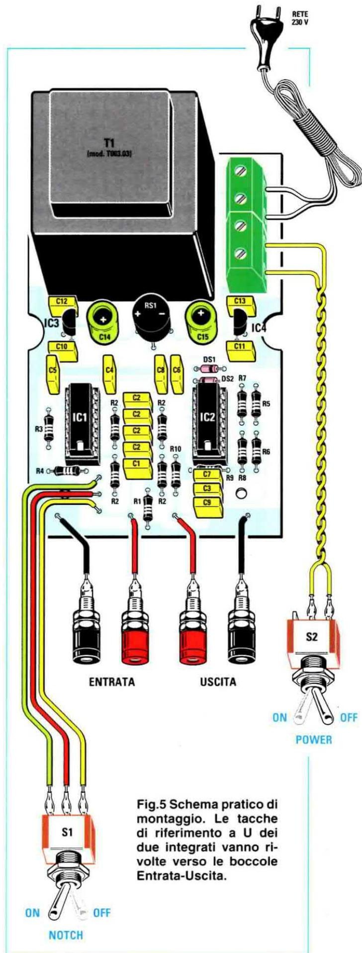
**Fig.5** Schema pratico di montaggio. Le tacche di riferimento a **U** dei due integrati vanno rivolte verso le boccole **Entrata-Uscita**.
