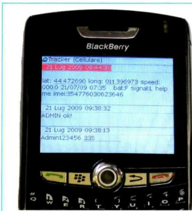
**Fig.13** Potete usare qualsiasi cellulare che trasmetta SMS. Non è obbligatorio disporre di palmare. Naturalmente un palmare del tipo riprodotto nella foto a lato è già corredato del programma **Google Map**, dal quale ricavare direttamente le coordinate del punto in cui è localizzato **TRACKER**.
