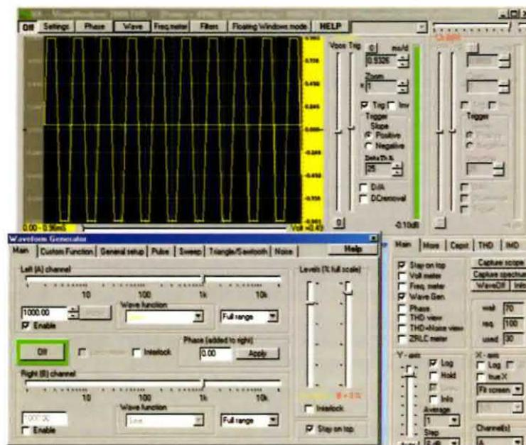
Fig.39 Se il cursore del **Levels** fosse regolato male potrebbe succedere che l'onda che appare sullo schermo dell'oscilloscopio anziché risultare perfettamente sinusoidale risulti **distorta**, come indicato in figura.
