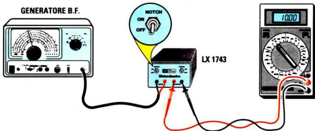
Fig.15 Se utilizzerete un Tester digitale dovreste prima sapere quale valore di Distorsione presenta la frequenza dei 1.000 Hz prelevata dal Generatore BF, quindi sposterete il deviatore S1 in posizione OFF e la manopola del Tester sulla portata 20 Volt DC. Di seguito ruotate la manopola del segnale d'uscita del Generatore BF fino a leggere sul Tester una tensione continua di 10,00 Volt.
