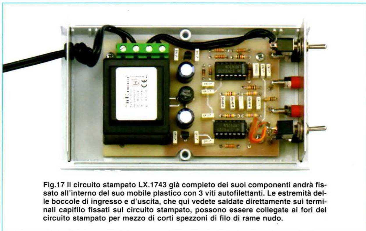
Fig.17 Il circuito stampato LX.1743 già completo dei suoi componenti andrà fissato all'interno del suo mobile plastico con 3 viti autofilettanti. Le estremità delle bocche di ingresso e d'uscita, che qui vedete saldate direttamente sui terminali capifilo fissati sul circuito stampato, possono essere collegate ai fori del circuito stampato per mezzo di corti spezzoni di filo di rame nudo.
