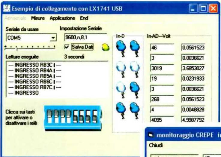
Fig.24 Cliccando su Monitor si apre la finestra a lato destinata al rilevamento delle crepe, dove potrete leggere i valori rilevati dai sensori nell'arco di tempo selezionato e vedere una piccola animazione.
