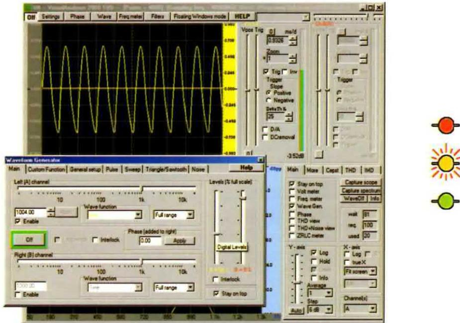
Fig.49 Dopo avere regolato l'ampiezza del segnale spostate lentamente il cursore **Left (A)** ancora verso destra, **augmentando** ancora la frequenza erogata dal generatore.
