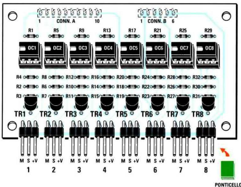
Fig.6 Schema pratico di montaggio dell'LX.1742. Per testare gli ingressi digitali potete inserire un ponticello tra S e +V. Un deviatore può simulare bene un ingresso in fase di test.
