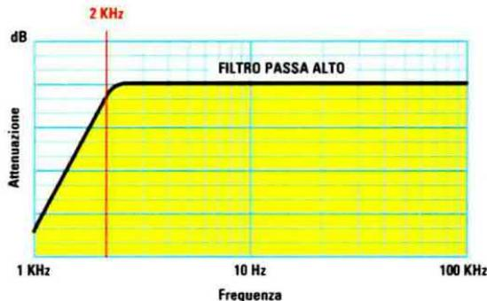
Fig.6 Questa è invece la curva di risposta del filtro passa alto. Il filtro passa alto è disegnato per lasciare passare, senza attenuazione, tutte le frequenze superiori a 2 kHz. Questo funzionamento è rappresentato dalla linea piatta del grafico. Le frequenze inferiori a 2 kHz vengono invece progressivamente attenuate fino a scomparire, come indicato dalla linea inclinata posta nella parte sinistra del grafico.
