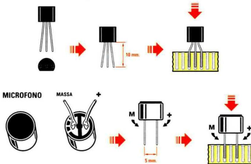
Fig.14 Ora dovrete inserire nella bassetta i **tre transistor BC547** siglati **TR1-TR2 e TR3**. Dopo averli prelevati dal kit osservateli: come vedete sono provvisti di terminali corrispondenti rispettivamente alla **base (B)**, all'**emettitore (E)** e al **collettore (C)**, vedi fig.8.
