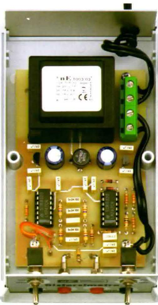
Fig.7 Foto del circuito stampato montato già fissato all'interno del mobile per mezzo delle viti autofilettanti inserite nel kit.
