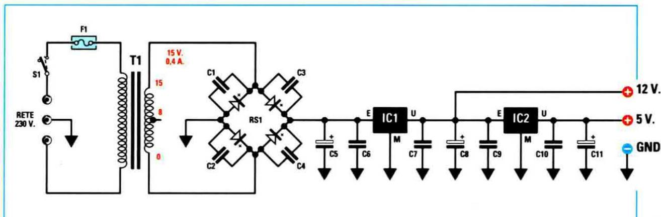
**Fig.4** Per questa applicazione abbiamo utilizzato uno dei nostri tanti alimentatori, in particolare l'**LX.1701**, corredato dell'elenco componenti.
