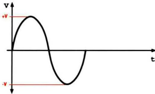
Fig.4 E' qui rappresentato l'andamento di una tensione sinusoidale che varia nel tempo tra il valore massimo +V e il valore minimo -V.
