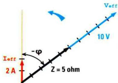
Fig.12 Dividendo la tensione efficace presente applicata all'impedenza per la corrente efficace che l'attraversa si ricava il suo valore assoluto  $Z$ , rappresentato in figura dalla freccia nera. In questo caso poiché la tensione vale 10 volt e la corrente 2 Ampere, il valore assoluto dell'impedenza  $Z$  è di 5 ohm.
