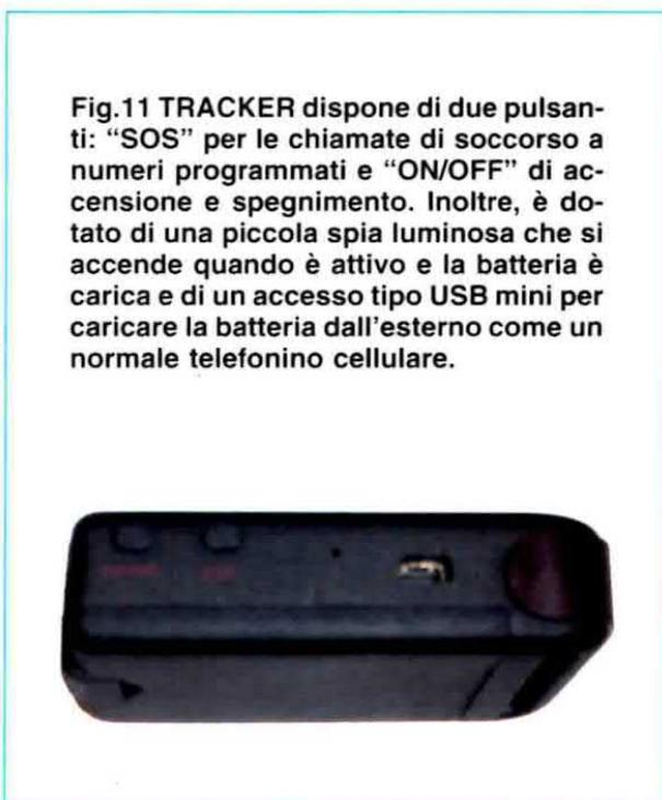
Fig.11 TRACKER dispone di due pulsanti: “SOS” per le chiamate di soccorso a numeri programmati e “ON/OFF” di accensione e spegnimento. Inoltre, è dotato di una piccola spia luminosa che si accende quando è attivo e la batteria è carica e di un accesso tipo USB mini per caricare la batteria dall'esterno come un normale telefonino cellulare.
