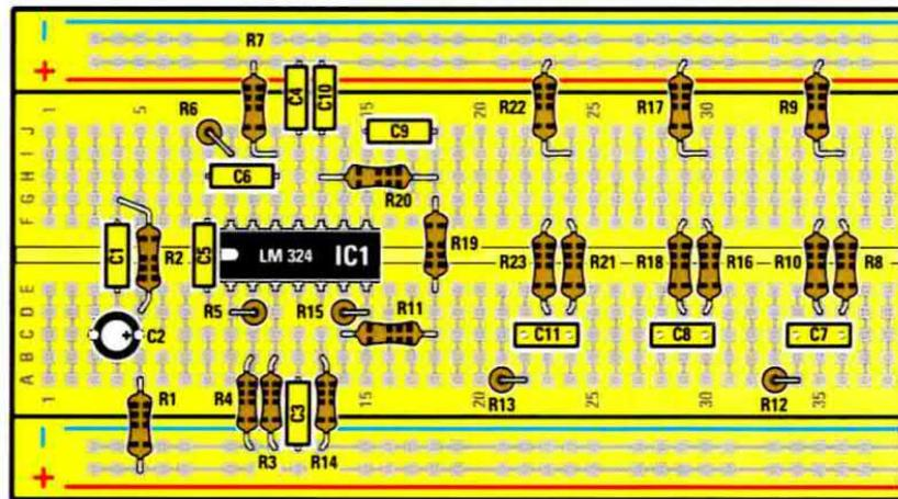
Fig.12 E' ora la volta delle **resistenze**, che potrete riconoscere facilmente osservando i **colori** stampigliati sul loro corpo.
