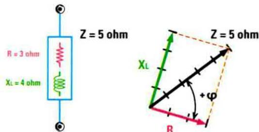
Fig.15 Anche in questo caso possiamo scomporre il vettore Z di 5 ohm nella componente resistiva R di 3 ohm e in quella reattiva XL di 4 ohm. Poiché ora la tensione risulta in anticipo sulla corrente di un angolo  $+ \varphi$ , la componente reattiva è di tipo induttivo, come indicato in figura.
