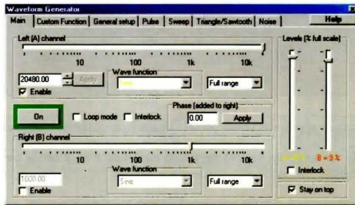
Fig.32 Se invece spostate il cursore completamente verso **destra**, nella stessa finestra vedrete comparire il valore **20480,00**. Questo significa che avete attivato il generatore ad una frequenza di **20.480 Hertz**.
