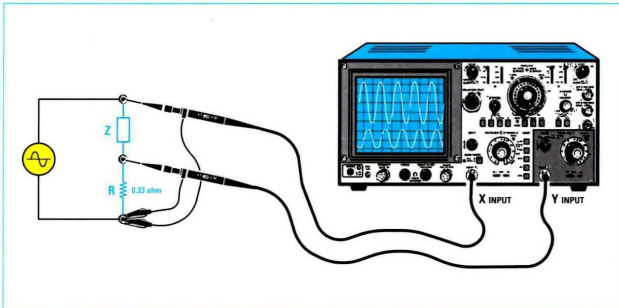
**Fig.6** Se poniamo in serie ad una impedenza una piccola resistenza da 0,33 ohm, collegando l'oscilloscopio come indicato in figura è possibile visualizzare sullo schermo due sinusoidi, una di ampiezza maggiore, che rappresenta la tensione presente ai capi dell'impedenza e l'altra più piccola, che rappresenta la corrente che l'attraversa. In questo modo è possibile visualizzare lo sfasamento esistente tra queste due grandezze.
