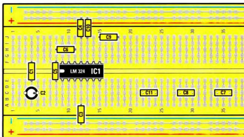
Fig.11 Prelevate dal kit i **10 condensatori poliestere C1-C3-C4-C5-C6-C7-C8-C9-C10-C11**.
