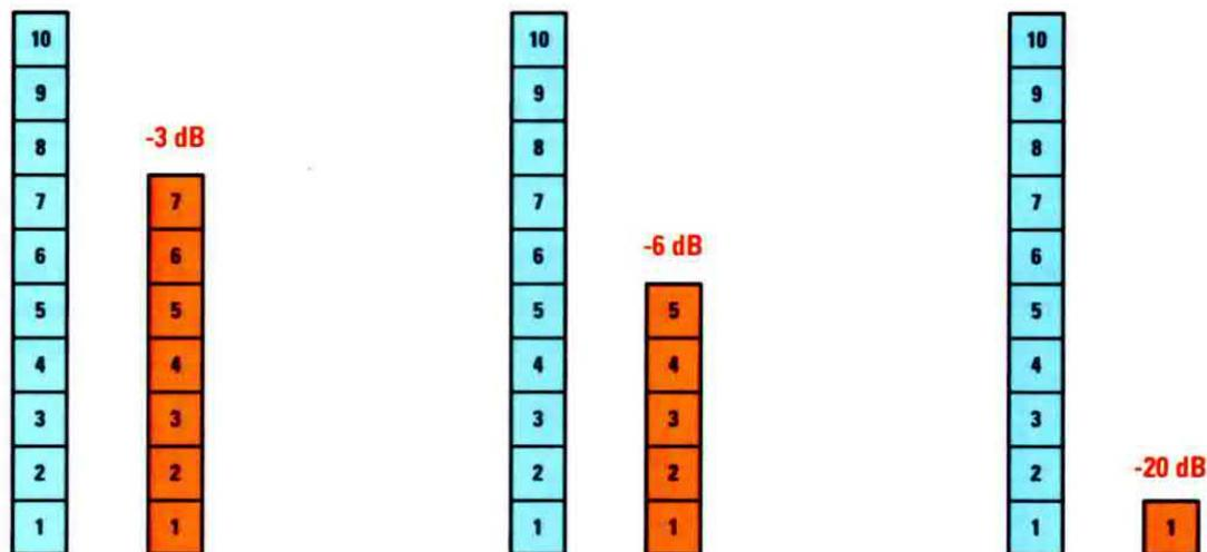
Fig.27 In questo disegno abbiamo riprodotto a titolo di esempio alcuni valori di **attenuazione** in **dB**. La colonna azzurra indica l'ampiezza in valore decimale della tensione di ingresso del filtro mentre la colonna rossa indica l'ampiezza in valore decimale della tensione di uscita.
