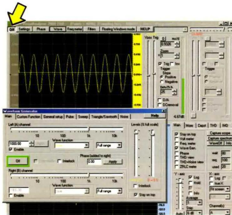
Fig.38 Tuttavia sullo schermo dell'oscilloscopio ancora **non compare** la forma d'onda prodotta dal generatore, perché occorre attivare l'oscilloscopio cliccando sul tasto **ON** posto in alto a sinistra sulla barra delle opzioni.
