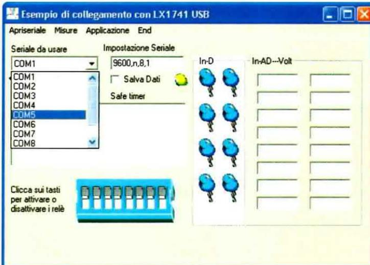
Fig.19 Selezionate la COM virtuale (per noi è la COM5) dal COMBO e cliccate di seguito su Apriserie.
