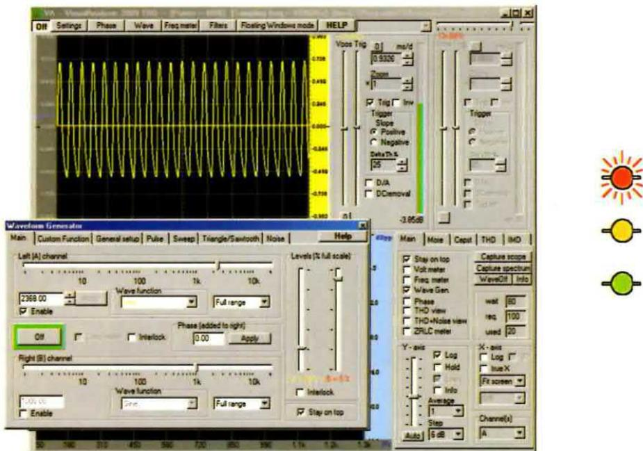
Fig.50 Ad un certo punto, superata la frequenza di circa **2.000 Hz**, vedrete che la luminosità del **led giallo** inizia a **ridursi**, ad indicare che abbiamo superato la frequenza di taglio superiore del filtro **passa banda**, che comincia ad attenuare, mentre inizia ad accendersi il diodo **led rosso**, perché entra in azione il filtro **passa alto**.
