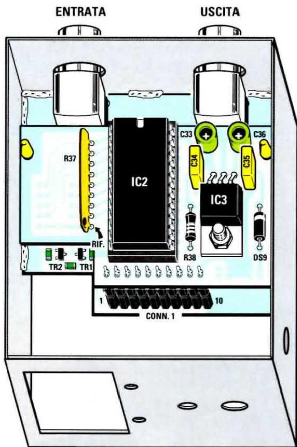
**Fig.11** Eseguita l'operazione descritta in fig.10, potrete procedere a fissare sulla scheda RF in SMD l' LX.1745 per mezzo del connettore CONN.1.
