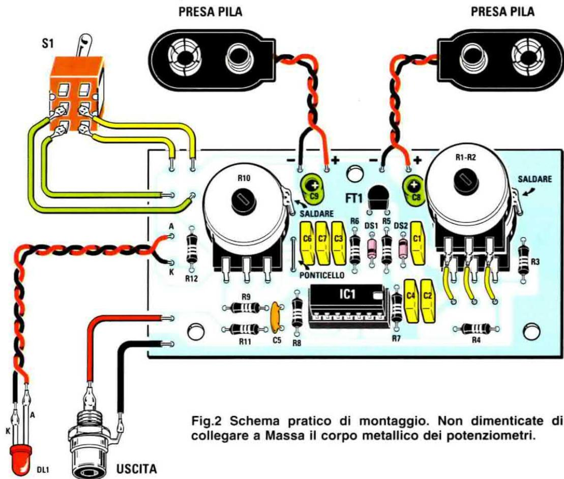
Fig.2 Schema pratico di montaggio. Non dimenticate di collegare a Massa il corpo metallico dei potenziometri.
