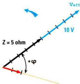
Fig.14 In questa figura abbiamo rappresentato il caso di una impedenza di tipo induttivo, nella quale la tensione, cioè il vettore di colore blu, risulta costantemente in anticipo di un angolo  $+ \varphi$  rispetto alla corrente che la attraversa raffigurata dal vettore rosso.
