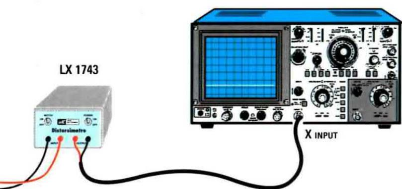
Fig.12 Per misurare la percentuale di Distorsione di un Amplificatore BF, sul suo ingresso andrà applicato il Generatore BF e alla Cassa Acustica l'ingresso del Distorsimetro LX.1743, mentre all'uscita di quest'ultimo un Oscilloscopio o un Tester digitale.
