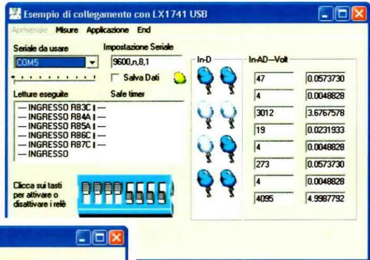
Fig.23 Spuntate salva Dati e agite sullo slider selezionando il tempo di salvataggio da 1 a 10 secondi. Grazie alla disponibilità del sorgente potrete eseguire modifiche e migliorie secondo le vostre necessità.
