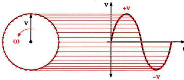
**Fig.10** Se facciamo ruotare una freccia, cioè un vettore, di ampiezza  $V$  intorno ad un suo estremo, descrivendo un cerchio con velocità angolare ( $\omega$ ) costante, e proiettiamo ad intervalli regolari la posizione dell'altro estremo del vettore su un diagramma cartesiano, otterremo una perfetta sinusoide.
