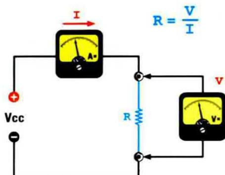
Fig.2 Come sapete, la misura della resistenza di un conduttore viene effettuata applicando ai suoi capi una tensione continua e misurando la corrente che lo attraversa.
