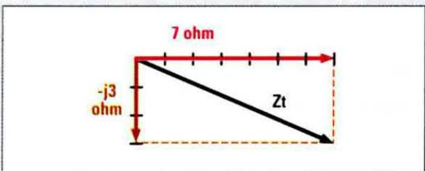
Se ora vogliamo ricavare il **modulo**, cioè il **valore assoluto** dell'impedenza **Z<sub>t</sub>**, basterà applicare il teorema di Pitagora alla figura precedente ed otterremo:
