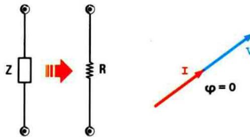
**Fig.9** Se l'impedenza che state misurando è di tipo resistivo, cioè è formata dalla sola resistenza  $R$ , la sinusoide della tensione, visibile nella parte alta dello schermo, risulterà invece perfettamente in fase con quella sottostante della corrente. Come potete notare, entrambe le sinusoidi raggiungono il massimo nello stesso istante  $t$ . In questo caso si dice che l'impedenza è di tipo puramente resistivo.
