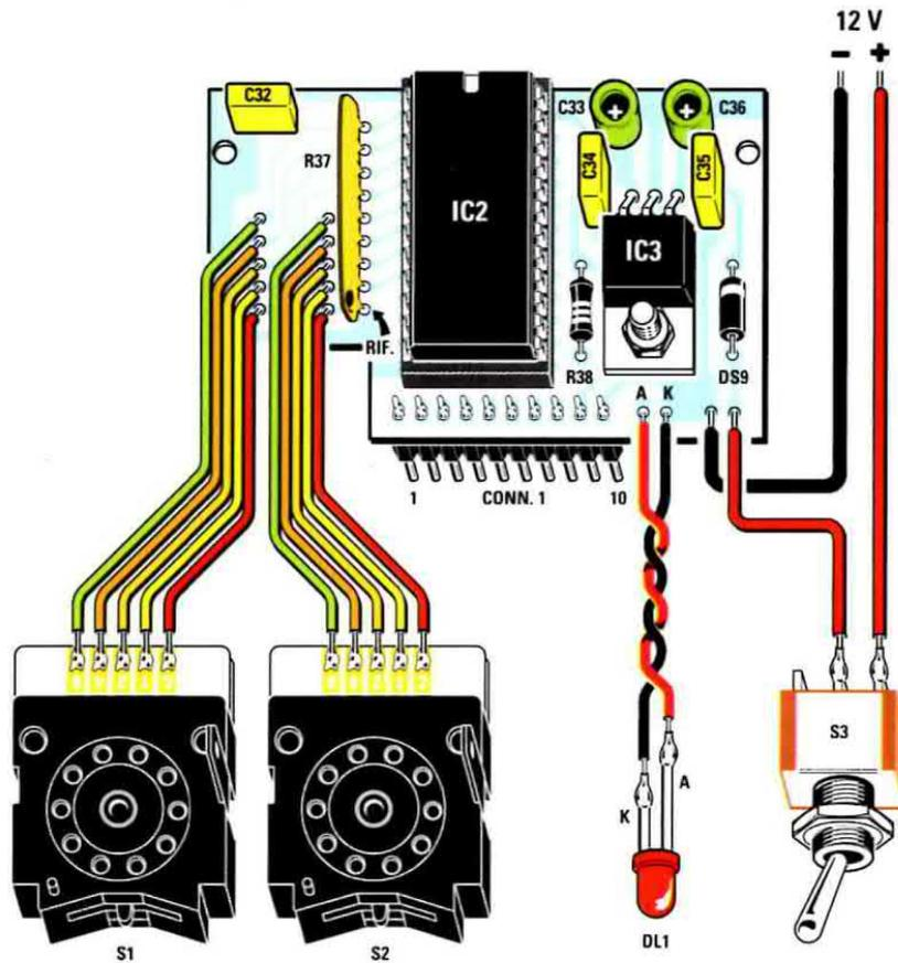
**Fig.8** Schema pratico di montaggio della scheda base LX.1745. Seguendo questa illustrazione e le indicazioni nel testo non incontrerete particolari difficoltà nel montare questa parte del progetto e nell'eseguire i collegamenti esterni.
