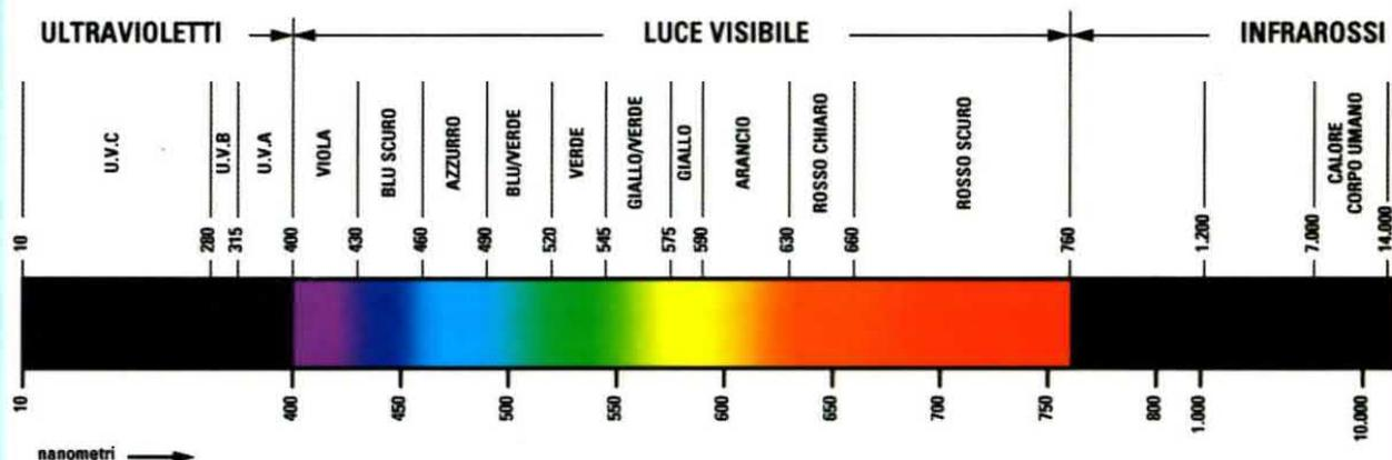
Fig.20 La figura ci permette di capire la composizione delle diverse onde elettromagnetiche che formano la luce solare in funzione della loro **lunghezza d'onda**, che si misura in **nanometri**, cioè in **miliardesimi di metro**.
