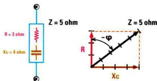
Fig.13 Il vettore impedenza di 5 ohm può essere scomposto in una componente resistiva  $R$  di 3 ohm e in una componente reattiva  $X_c$  di 4 ohm, ortogonali fra loro. Poiché la tensione è in ritardo sulla corrente, l'angolo  $\varphi$  è negativo e quindi la componente reattiva è di tipo capacitivo, come indicato in figura.
