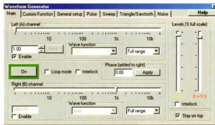
Fig.31 Dovete sapere che all'interno del **VA** sono presenti **due distinti generatori BF**, uno contrassegnato dalla dicitura **Left (A) channel** e l'altro dalla dicitura **Right (B) channel**. Le diciture derivano dal fatto che i generatori possono essere utilizzati per provare i due **canali Left e Right** di un **amplificatore audio**.
