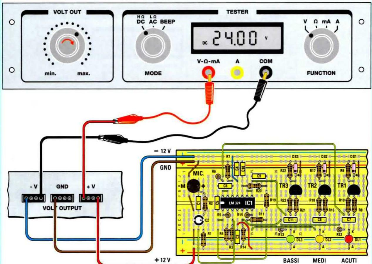
Fig.18 Ora accendete il Minilab. Ruotate piano la manopola **VOLT OUT** in senso **orario** fin quando non leggerete sul **display** del **tester** un valore il più possibile vicino a **24,00**. Sappiate che non è indispensabile ottenere esattamente il valore **24,00** ma basterà che il valore sul display sia compreso tra **23** e **24 Volt**. In questo modo avete fornito al circuito l'**alimentazione duale** di **+/-12 Volt** necessaria per il suo funzionamento.
