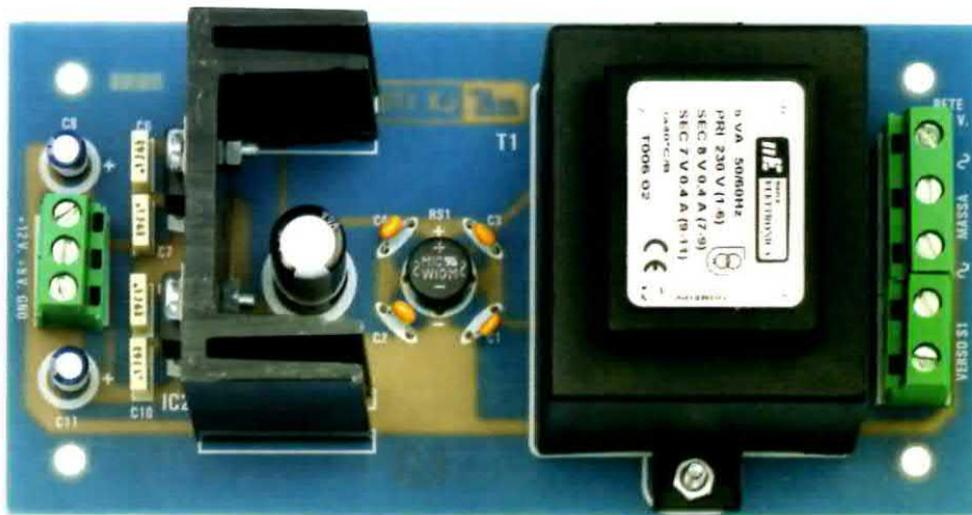
Fig.11 L'alimentatore LX.1701, nato per il Generatore DDS, fornisce le due alimentazioni che servono alla scheda USB per mezzo di due stabilizzatori. Così montati su un'aletta possono fornire fino a 1 Ampere di corrente: anche troppo per la maggior parte delle applicazioni!
