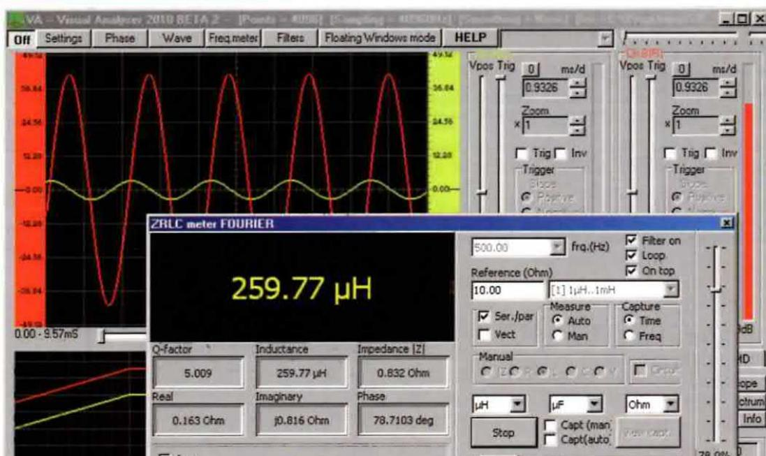
Fig.1 L'impedenzometro consente non solo di misurare con precisione il valore di qualsiasi condensatore o induttanza, ma anche di ricavare il loro Q, cioè il fattore di merito, che esprime in una certa misura la "bontà" del componente. Eviterete così di utilizzare un componente in modo inappropriato.
