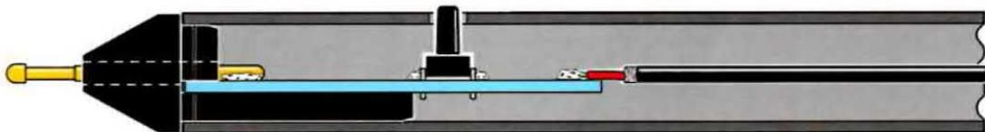
Fig.8 Esercitate una leggera pressione sul tappo conico in modo da chiudere il tubo e da far fuoriuscire l'estremità dell'elettrodo dorato.
