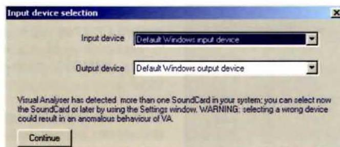
significa che il software ha rilevato la presenza di più di una scheda audio all'interno del vostro pc. Per utilizzare il software dell'impedenziometro è quindi necessario selezionare la scheda audio denominata **USB Audio CODEC**, presente all'interno della scheda **KM1667**.
