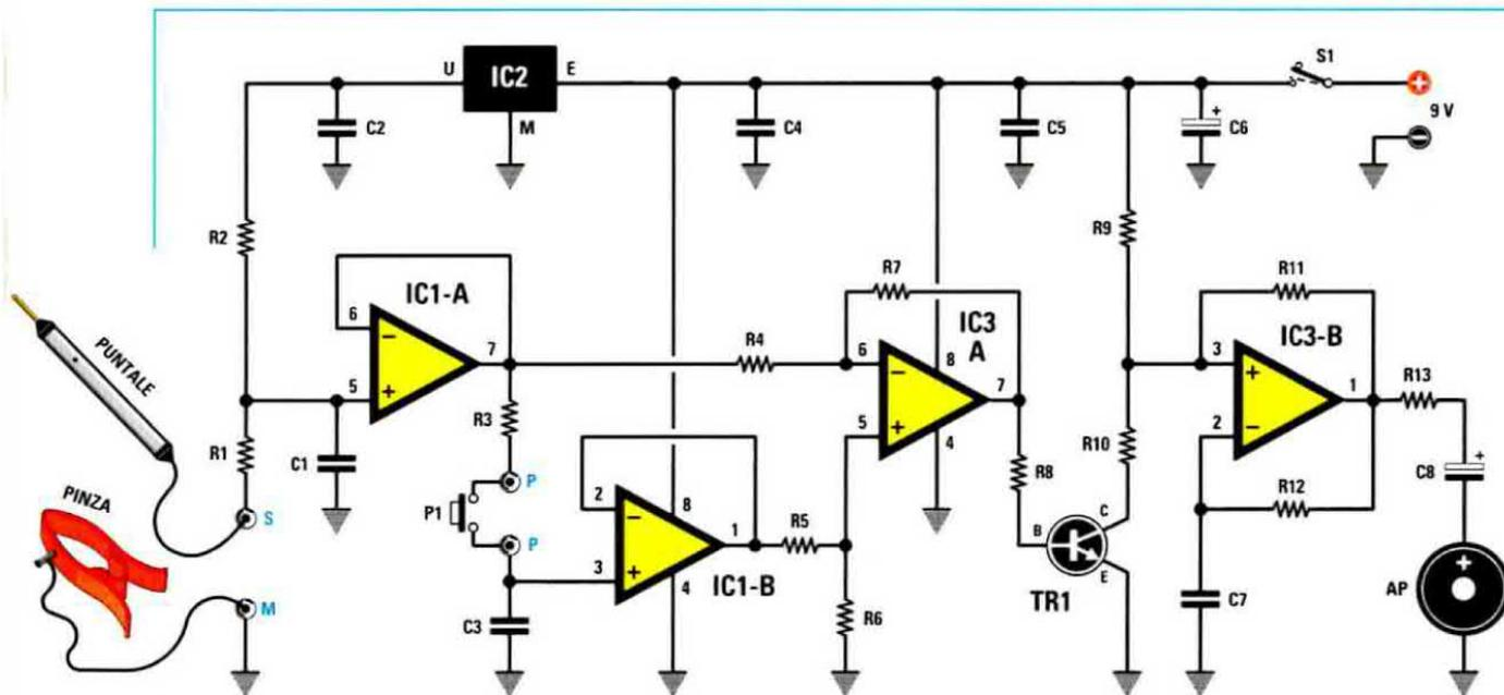
Fig.2 Schema elettrico dell'LX.1751, un circuito sofisticato sviluppato mediante l'utilizzo di 2 soli integrati. Ricordiamo che il terminale di massa va collegato al paziente per mezzo di una apposita pinza (o ventosa) visibile a sinistra nel disegno.
