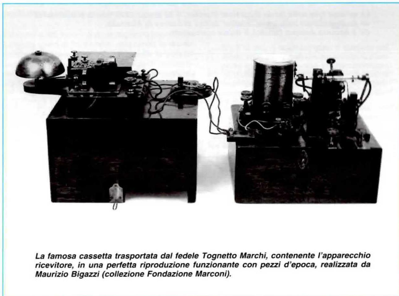
La famosa cassetta trasportata dal fedele Tognetto Marchi, contenente l'apparecchio ricevitore, in una perfetta riproduzione funzionante con pezzi d'epoca, realizzata da Maurizio Bigazzi (collezione Fondazione Marconi).
