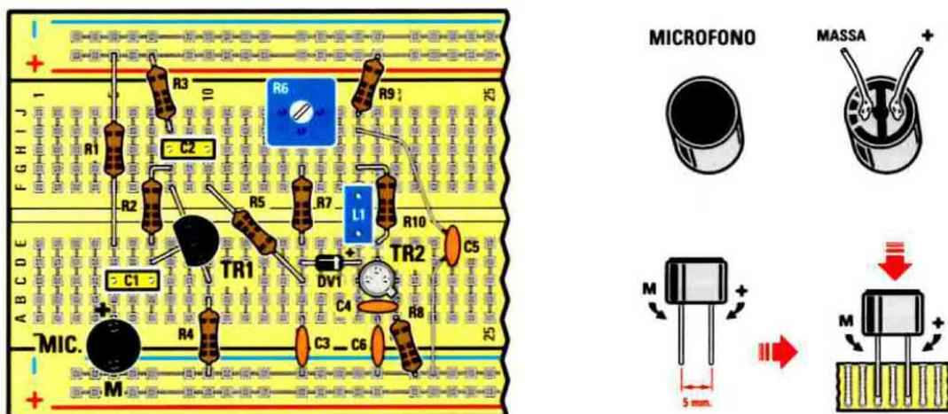
Fig.17 Da ultimo non vi resta che montare il **microfono**. Dopo averlo prelevato, ruotatelo in modo da osservare il lato da cui fuoriescono i suoi due terminali.
