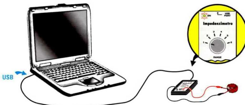
Dopo avere effettuato il collegamento alla porta **USB** del pc verificate che il **diodo led** posto sulla scheda **LX.1746** dell'impedenziometro sia **acceso**, a conferma della corretta alimentazione.
