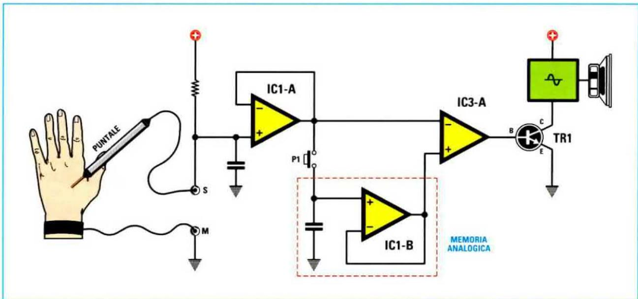
**Fig.3** Schema a blocchi del cercapunti elettronico. Con il tratteggio rosso abbiamo evidenziato la memoria analogica, che rimane inalterata fino a quando non viene premuto il pulsante per eseguire una nuova misura.
