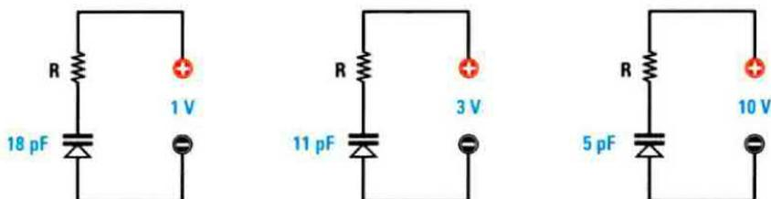
Fig.10 In questo esempio abbiamo applicato al catodo del diodo varicap una tensione positiva di 1-3-10 Volt e la sua capacità è passata rispettivamente da 18 a 11 e infine a 5 pF.
