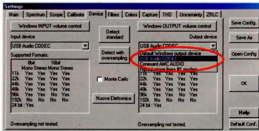
**Nota:** la procedura di abilitazione della scheda LX.1746 che abbiamo descritto deve essere eseguita ogni volta che viene lanciato il software operativo. In caso contrario la misura non può essere eseguita perché manca il riconoscimento dell'impedenziometro da parte del pc.
