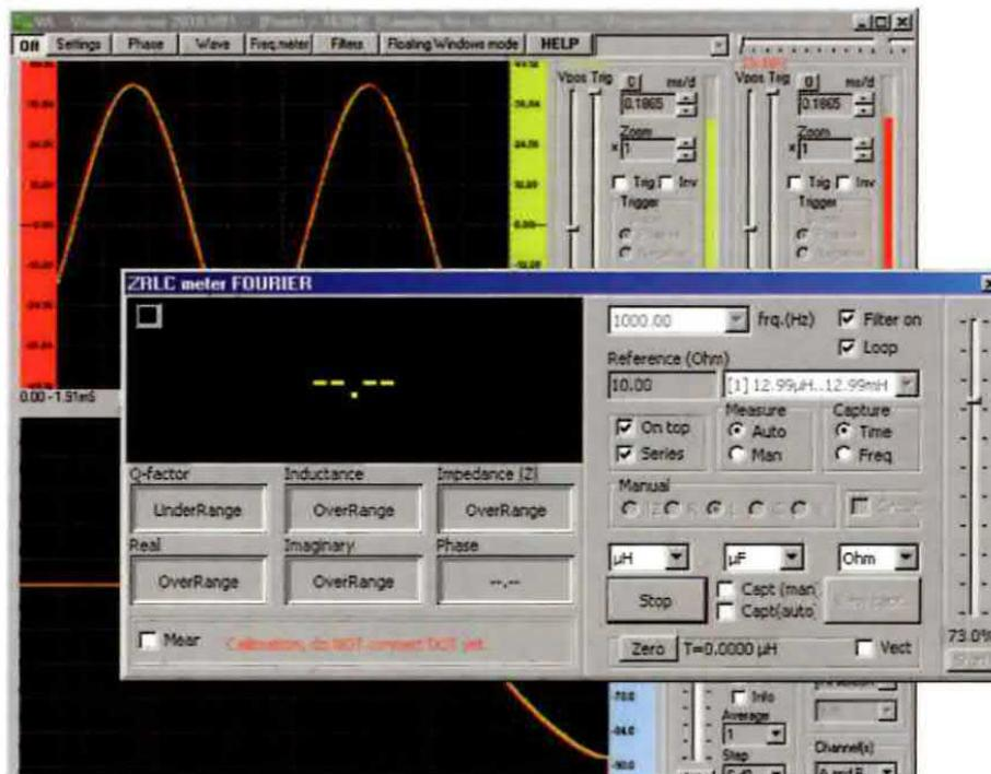
Questo significa che lo strumento sta eseguendo la **calibrazione**, durante la quale va a verificare se l'ampiezza della sinusoide di misura è corretta ed esegue l'**equalizzazione** dei due canali del convertitore **USB**.
