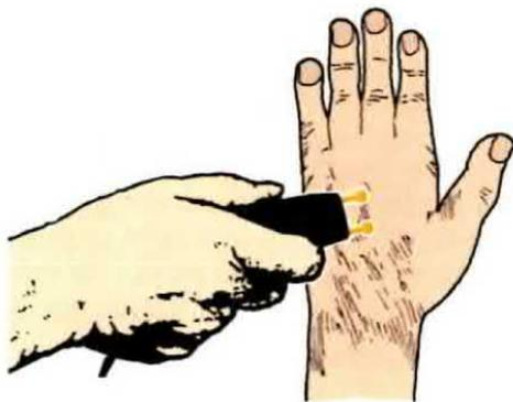
Fig.13 Effettuando la misura dell'impedenza sulla mano potreste riscontrare una notevole differenza fra i valori misurati sul dorso ed i valori misurati sul palmo.
