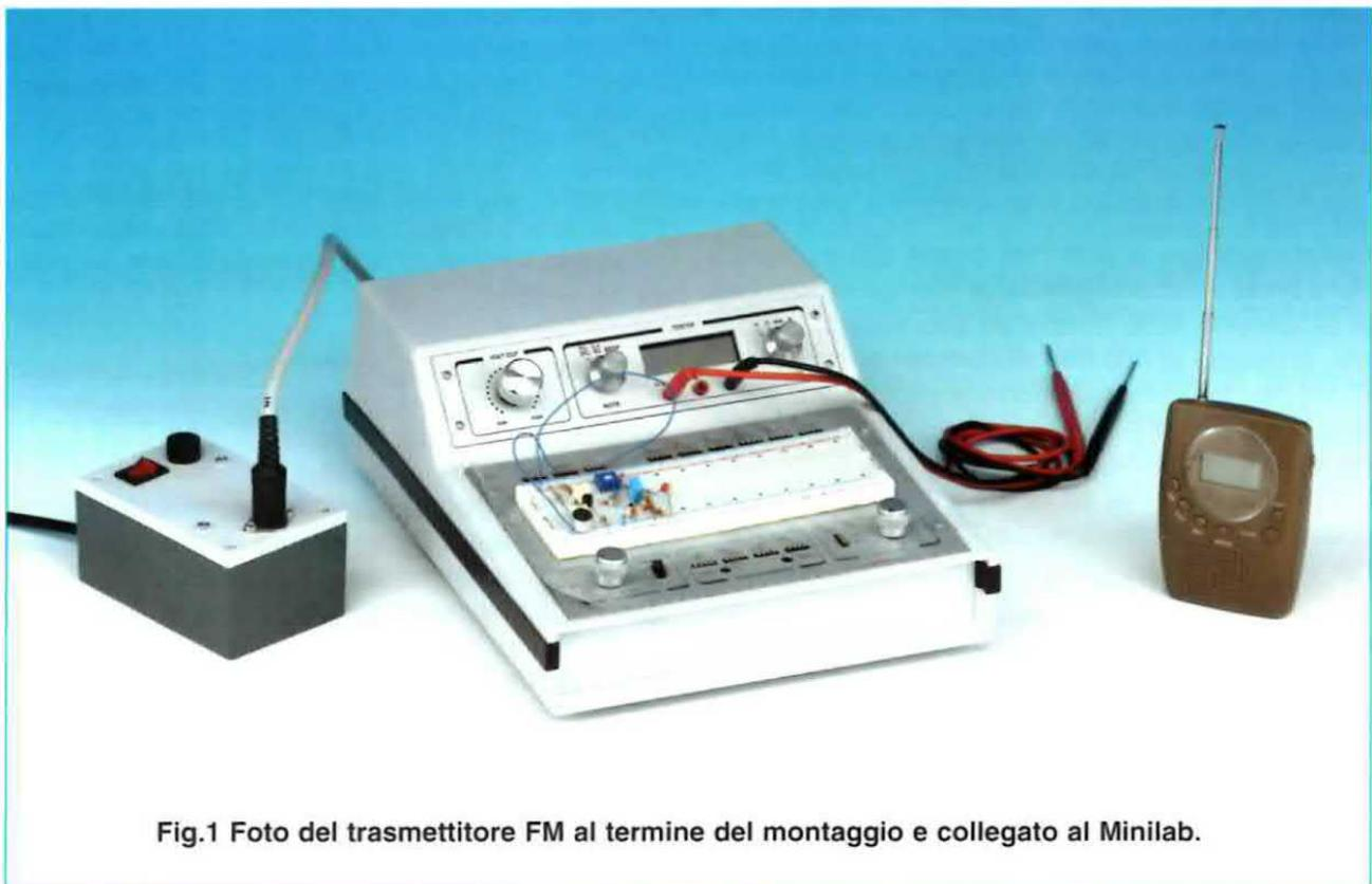
Fig.1 Foto del trasmettitore FM al termine del montaggio e collegato al Minilab.
