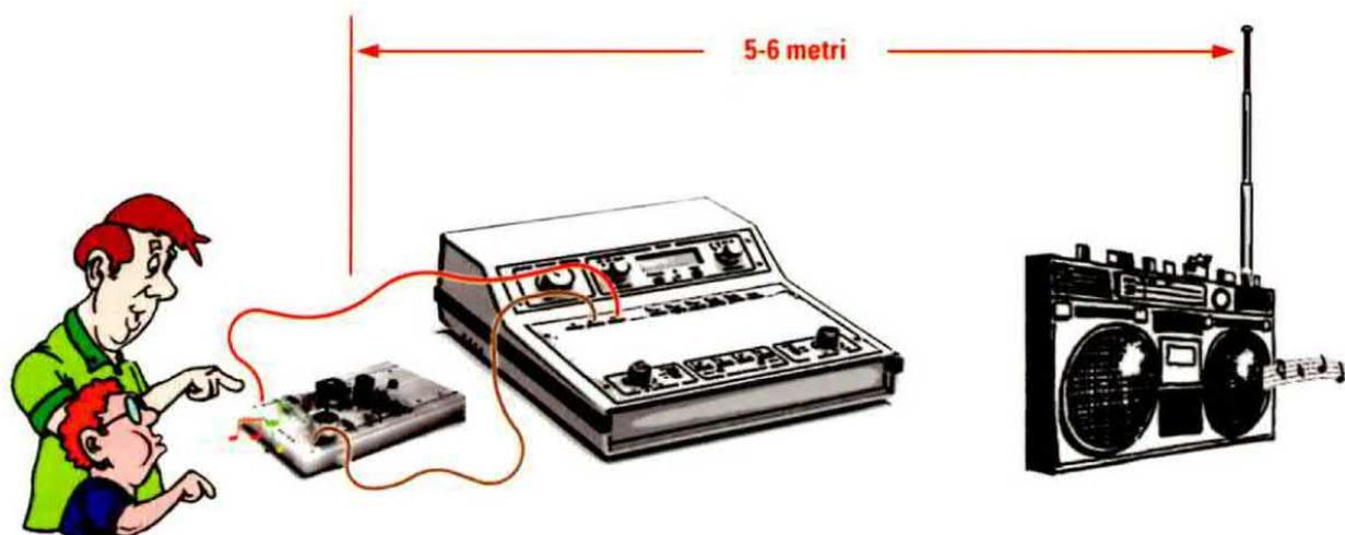
Fig.22 Se avete eseguito correttamente l'operazione di sintonia, sarete in grado di udire con la radio parole e suoni inviati dal trasmettitore.
