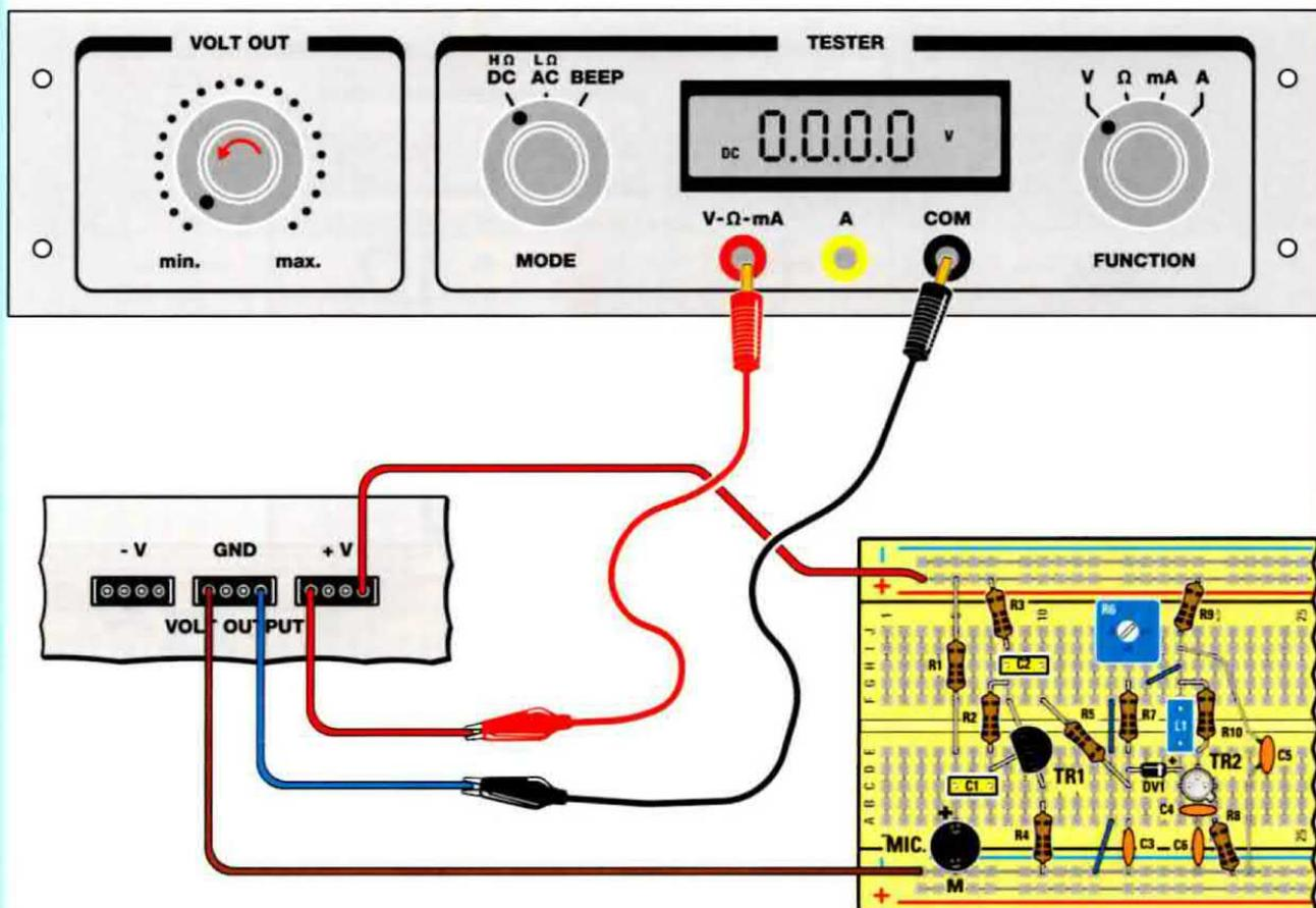
Fig.19 Giunti a questo punto dovete collegare la breadboard all'**alimentatore del Minilab**. Per fare questo collegate il filo **marrone** della **massa** ad uno qualsiasi dei 4 fori del connettore siglato **GND**.
