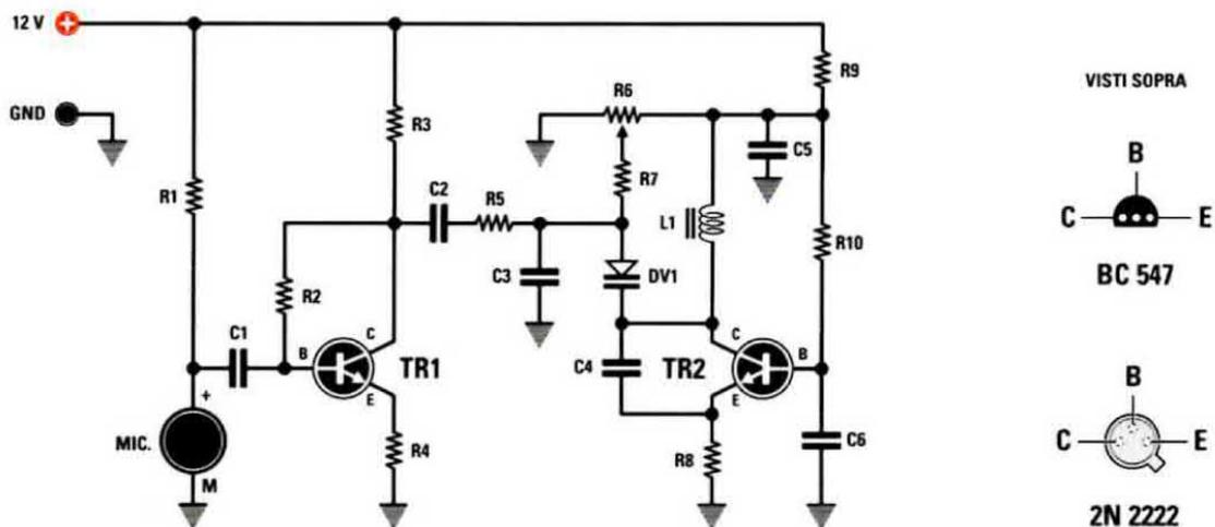
**Fig.11** Questo è lo schema elettrico del nostro piccolo trasmettitore. Sulla destra potete notare il circuito oscillatore formato dalla induttanza L1, dal diodo varicap DV1, dal condensatore C4 e dal transistor TR2. Il trimmer R6 consente di regolare la sintonia, cioè la frequenza della portante.
