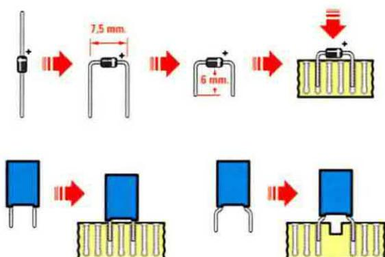
Fig.16 Prelevate ora dal kit il **diodo varicap DV1** e la minuscola **induttanza da 0,1 microHenry L1**, che potrete riconoscere per il corpo costituito da un piccolo parallelepipedo di plastica azzurra.
