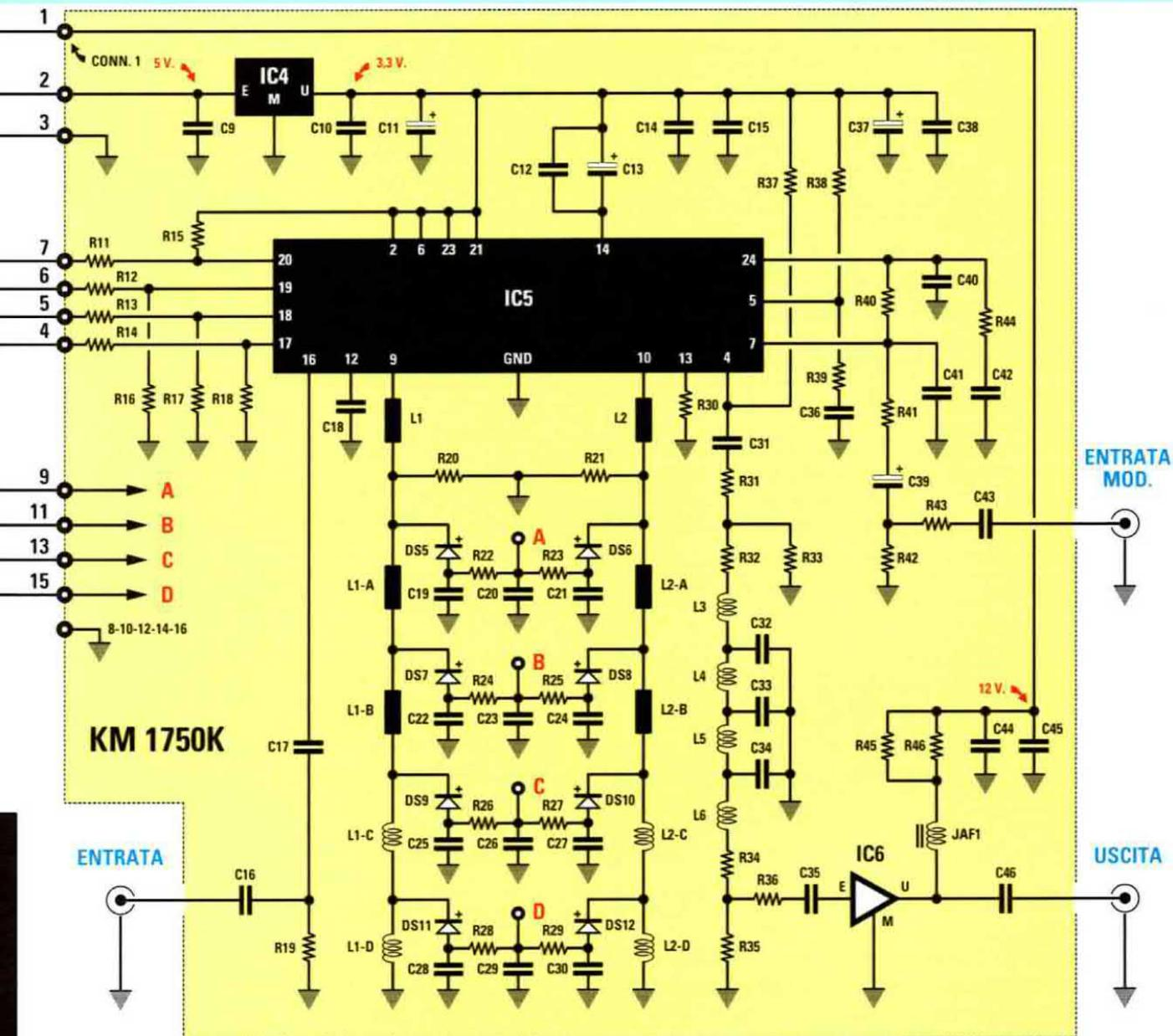
Fig.10 Tutti i componenti racchiusi in questo riquadro colorato sono montati nella scheda siglata KM.1750K che vi forniamo già collaudata (vedi figg.11-12).
