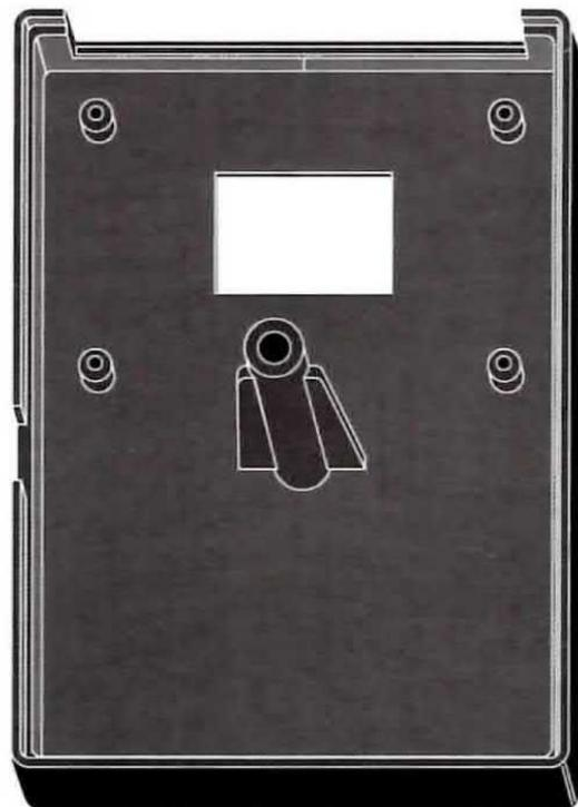
Successivamente, non dovrete fare altro che applicare al di sopra dello strumento il circuito stampato, come indicato in figura, facendo coincidere i due fori presenti sullo stampato con i due riscontri del mobile. A questo punto potrete procedere al suo fissaggio mediante le due viti fornite a corredo nel kit.
