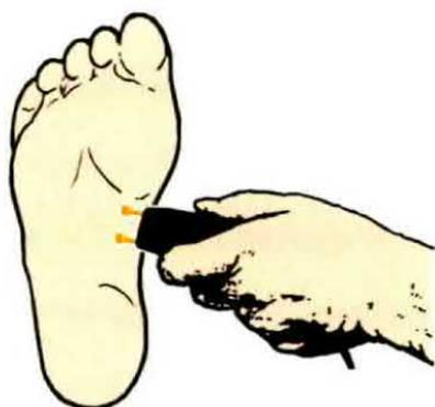
**Fig.18** Misurando la pelle della pianta dei piedi potrete rilevare un valore di impedenza piuttosto alto. Questo è abbastanza prevedibile, perchè la parte superficiale della cute in questa parte del corpo risulta particolarmente ricca di cellule morte.
