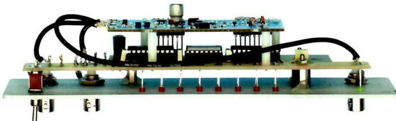
Fig.17 Foto del pannello frontale con sopra già applicate le schede LX.1750 e KM.1750K. Come potete osservare nel disegno di fig.18, per bloccare scheda LX.1750 su questo pannello dovreste utilizzare il dado dell'interruttore a levetta S1 (vedi figg.14-16) e i dadi dei distanziatori metallici fissati sul pannello. Per bloccare il circuito stampato in SMD siglato KM.1750K utilizzerete i distanziatori plastici a stilo inseriti nel kit.
