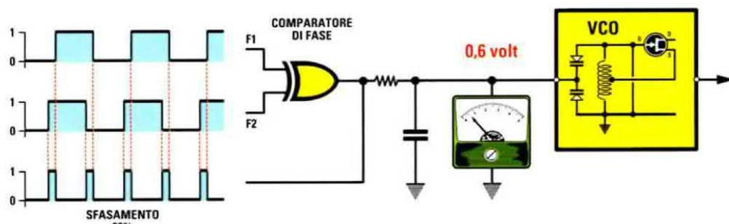
Fig.6 Quando su uno dei due ingressi dell'Or Esclusivo giunge un'onda quadra che risulta "sfasata" del 20% rispetto all'onda quadra che giunge sull'opposto ingresso, sui diodi Varicap sarà presente una tensione di  $(3 \times 20) : 100 = 0,6$  Volt.
