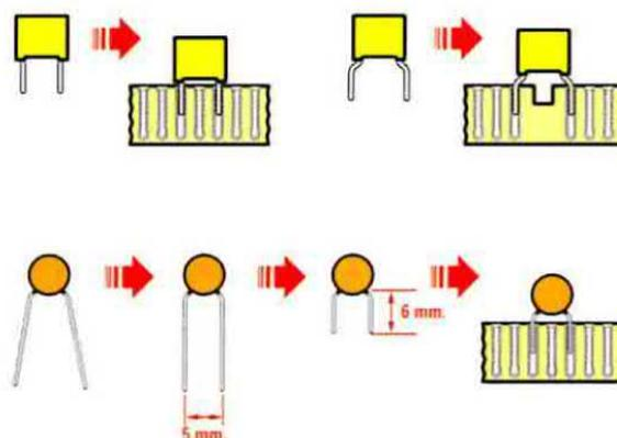
Fig.15 Ora inserite i **2 condensatori poliestere C1-C2**. Vi ricordiamo che i condensatori **poliestere non hanno polarità**, e pertanto i loro piedini possono essere **scambiati tranquillamente tra loro**. Nell'elenco componenti di fig.11 sono indicati i valori di capacità di entrambi i condensatori in **nanoFarad**.
