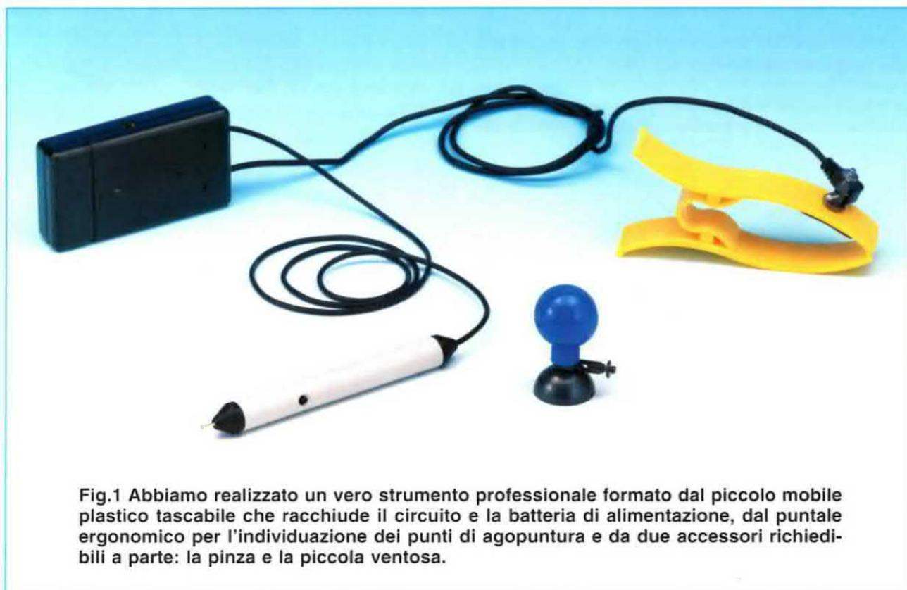
Fig.1 Abbiamo realizzato un vero strumento professionale formato dal piccolo mobile plastico tascabile che racchiude il circuito e la batteria di alimentazione, dal puntale ergonomico per l'individuazione dei punti di agopuntura e da due accessori richiedibili a parte: la pinza e la piccola ventosa.
