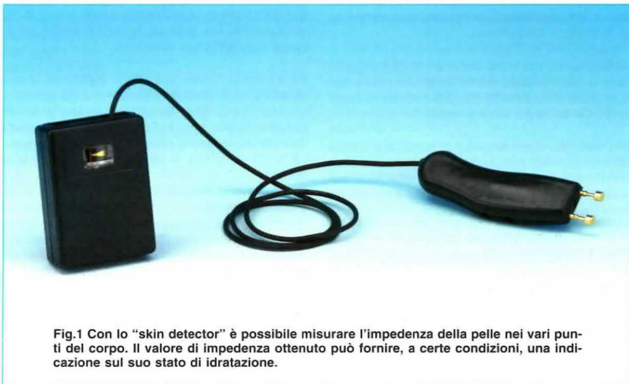
Fig.1 Con lo "skin detector" è possibile misurare l'impedenza della pelle nei vari punti del corpo. Il valore di impedenza ottenuto può fornire, a certe condizioni, una indicazione sul suo stato di idratazione.
