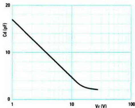
**Fig.12** In questo grafico è rappresentata la variazione di capacità in funzione della tensione applicata al catodo del diodo varicap impiegato sul nostro trasmettitore.
