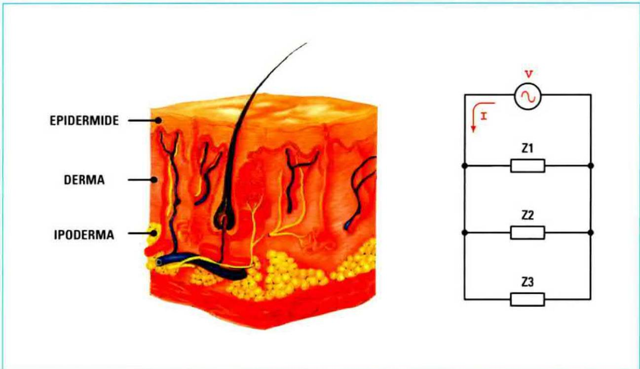
**Fig.2** Gli strati che formano la pelle presentano un diverso comportamento rispetto alla conduzione della corrente elettrica, che dipende dalla loro composizione fisico-chimica, dalla presenza di acqua, di sali minerali, ecc. Quando si esegue la misura dell'impedenza, è come se le impedenze dei vari strati fossero tra loro collegate in parallelo, influenzandosi reciprocamente.
