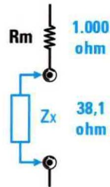
Poiché generalmente non si conosce il valore dell'impedenza da misurare, la regola che vi consigliamo di seguire è quella di effettuare una prima misura che vi fornisca il valore in ohm della vostra impedenza e poi di scegliere il valore della resistenza di precisione più prossimo al valore che avete misurato.
