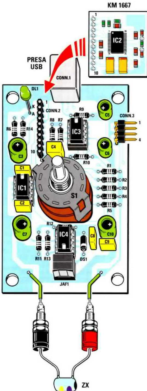
Fig.4 Una volta terminato il montaggio del circuito LX.1746 dovrete inserire nel connettore femmina a 10 poli CONN.2 il piccolo circuito in SMD KM1667, che abbiamo già pubblicato nella rivista N.231. Fate molta attenzione, durante questa operazione, a non danneggiare involontariamente i piedini.
