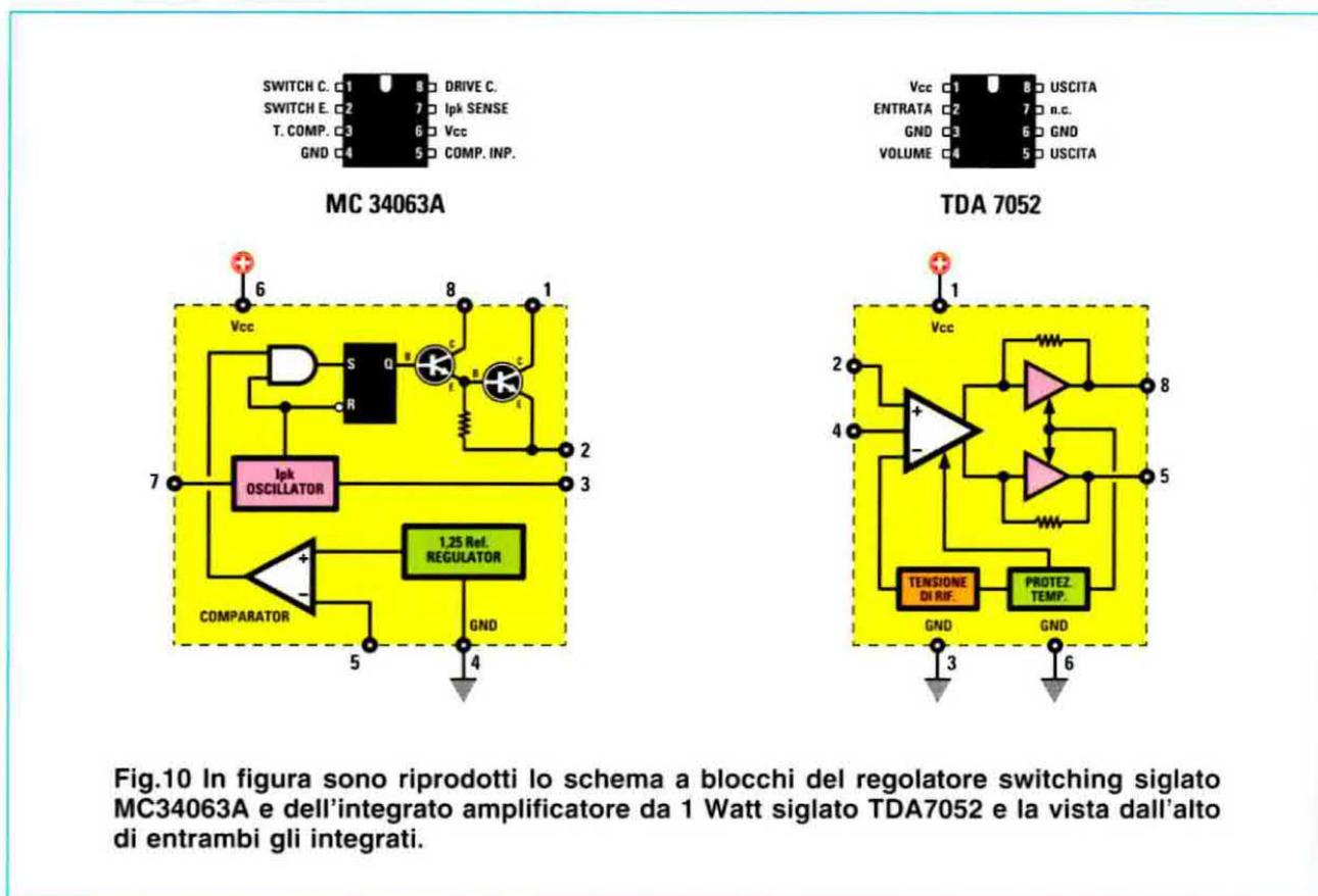
Fig.10 In figura sono riprodotti lo schema a blocchi del regolatore switching siglato MC34063A e dell'integrato amplificatore da 1 Watt siglato TDA7052 e la vista dall'alto di entrambi gli integrati.
