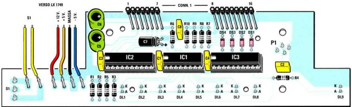
**Fig.13** Schema pratico di montaggio della scheda siglata LX.1750. Prima di fissare i terminali dei due connettori femmina CONN.1 da 7 e 9 terminali (vedi in alto) che, come potete notare nel disegno, risultano alquanto distanziati dal circuito stampato, conviene inserire in loro interno i connettori maschi del circuito KM.1750K (vedi fig.16) per poterne determinare l'esatta lunghezza.
