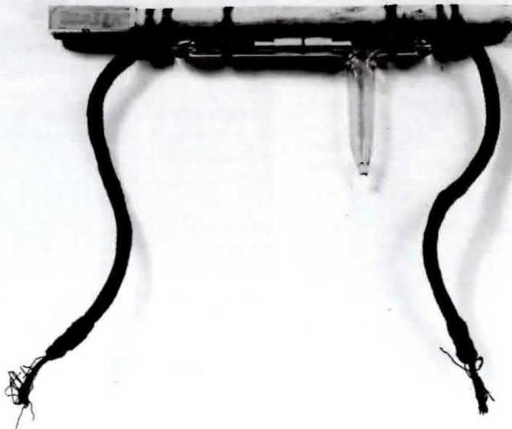
**Questo è il "coherer" che Guglielmo Marconi perfezionò, e che utilizzò come rivelatore nel suo apparecchio ricevitore. Era costituito da un tubetto di vetro riempito in origine di limatura di ferro, che Marconi sostituì con una miscela di argento e nichel, rendendolo più sensibile.**
