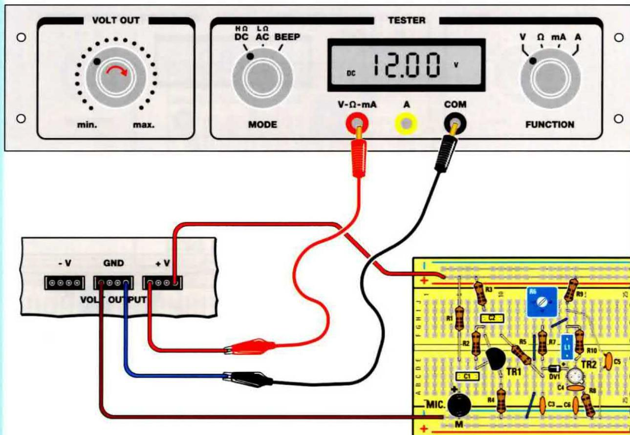
Fig.20 Ora accendete il Minilab. Ruotate piano la manopola **VOLT OUT** in senso **orario** fin quando non leggerete sul **display** del **tester** un valore il più possibile vicino a **12,00**. Sappiate che non è indispensabile ottenere esattamente il valore **12,00**, ma basterà che il valore sul display sia compreso tra **11** e **12 Volt**. In questo modo avete fornito al circuito l'**alimentazione** di **+12 Volt** necessaria per il suo funzionamento.
