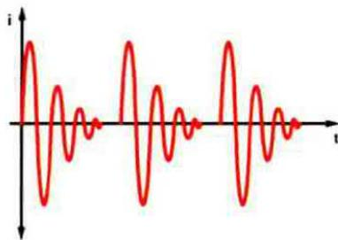
Fig.7 Se spostiamo alternativamente il deviatore dalla posizione A alla posizione B, produrremo nel circuito una serie di onde sinusoidali smorzate che si susseguono come quelle rappresentate in figura.
