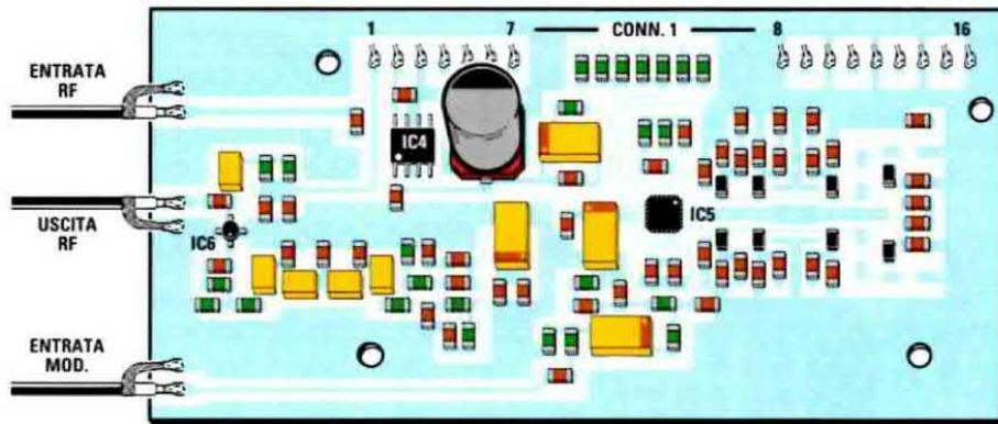
Fig.11 In questo disegno sono visibili tutti i componenti in SMD montati scheda KM.1750K. Alle piste poste a sinistra vanno collegate le estremità dei cavi coassiali per l'Entrata RF per l'Uscita RF e per l'Entrata Modulazione.
