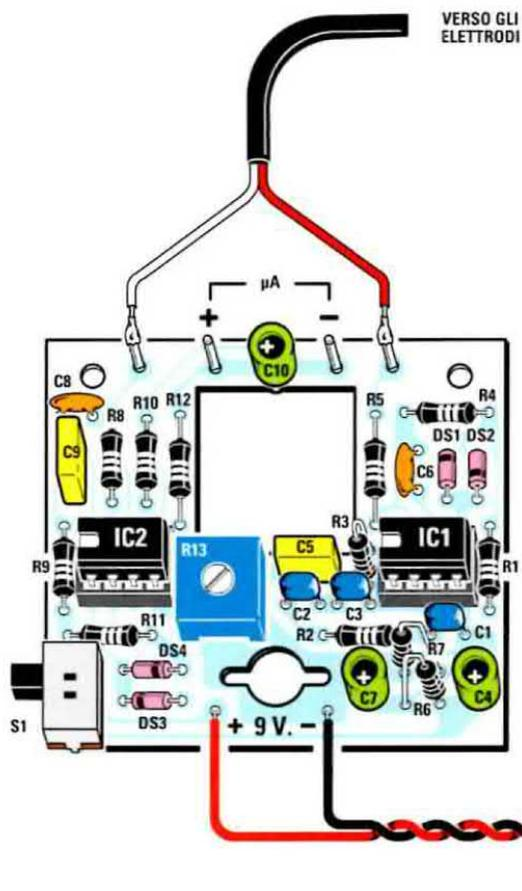
Fig.5 In figura è rappresentato il circuito LX.1748 a montaggio ultimato. Al centro è visibile il trimmer R13 da 2.000 ohm che viene utilizzato per eseguire la taratura fondo scala del microamperometro. Sul lato sinistro è visibile l'interruttore di accensione S1.
