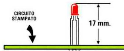
Fig.7 Prima di saldare i due terminali del diodo led DL1 sul circuito stampato, controllate che il suo corpo risulti distanziato 17 mm circa da esso.
