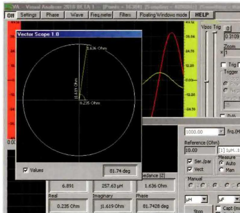
Nella finestra del vettorscopio sono rappresentate i due vettori che formano l'impedenza e cioè la **componente resistiva R**, posta sull'**asse orizzontale** del grafico, che in questo caso vale **0,235 ohm**, la **componente reattiva XI**, posta sull'**asse verticale** verso l'**alto**, che vale **1,619 ohm** e infine l'**impedenza risultante Z** che vale **1,636 ohm**.
