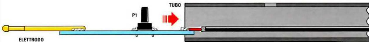
Fig.5 Come prima operazione inserite la porzione di circuito stampato all'interno del tubo come illustrato nel disegno.
