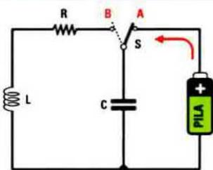
Fig.5 Questo è lo schema di un semplice circuito oscillatore, formato da un condensatore C, da una induttanza L e da una resistenza R. Portando il deviatore sulla posizione A, il condensatore si carica alla tensione della pila.
