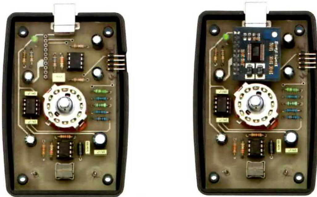
Fig.8 Una volta terminato il montaggio, il circuito andrà collocato sul fondo del mobile, facendo coincidere i fori sul circuito con gli appositi riscontri in plastica e avendo cura di fare fuoriuscire il connettore CONN.3 dalla fenditura a lato. A destra, il montaggio è completato dalla scheda KM1667 in SMD.
