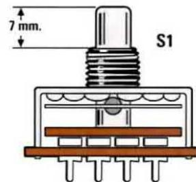
Fig.6 Prima di inserire i terminali del commutatore rotativo S1 nei fori presenti sul circuito stampato, dovrete segare il suo lungo perno per portarlo ad una lunghezza di soli 7 mm.
