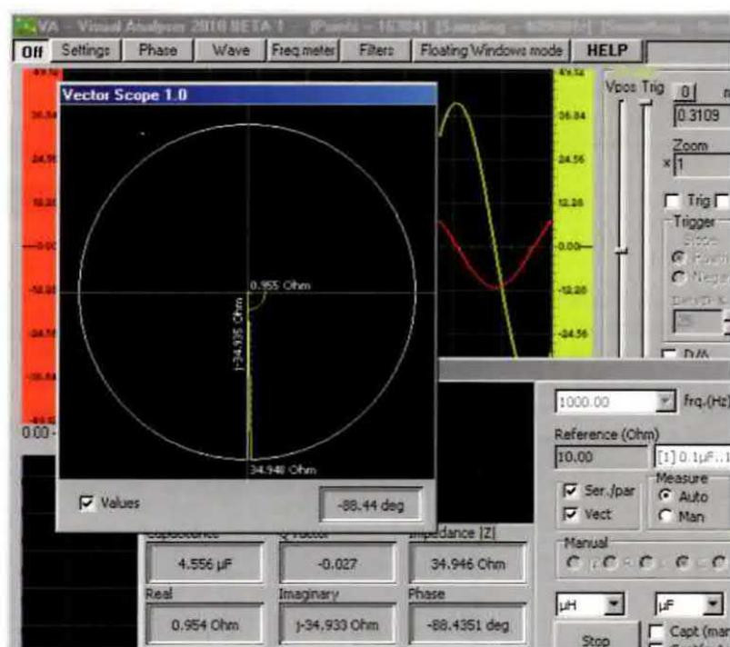
nella quale vedete rappresentate in **forma vettoriale**, la **componente resistiva R**, che vale **0,955 ohm**, la componente **reattiva Xc** che vale **- j 34,935 ohm**, e l'impedenza risultante **Z**, corrispondente a **34,946 ohm**.
