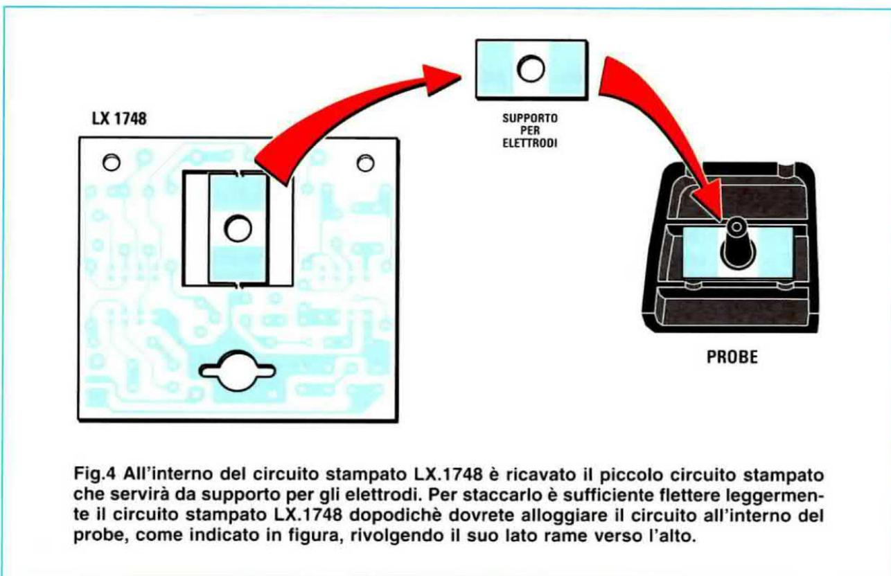
**Fig.4** All'interno del circuito stampato LX.1748 è ricavato il piccolo circuito stampato che servirà da supporto per gli elettrodi. Per staccarlo è sufficiente flettere leggermente il circuito stampato LX.1748 dopodichè dovrete alloggiare il circuito all'interno del probe, come indicato in figura, rivolgendo il suo lato rame verso l'alto.
