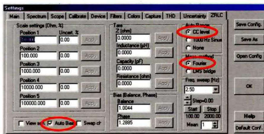
In questa finestra è possibile selezionare alcuni parametri utilizzati dall'impedenziometro in fase di **misura**. Per il corretto funzionamento dello strumento dovrete inserire i seguenti parametri:
