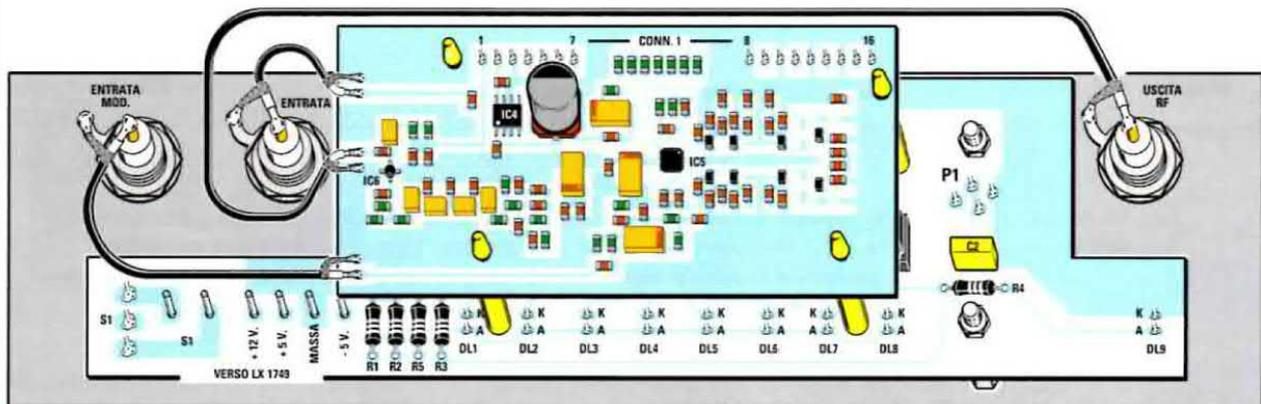
Fig.19 Sul circuito stampato in SMD siglato KM.1750K dovrete saldare sulle piste visibili in disegno, tre spezzoni di cavetto coassiale che poi collegherete ai BNC posti sul pannello indicati Entrata Mod. - Entrata RF e Uscita RF (vedi anche la fig.11).
