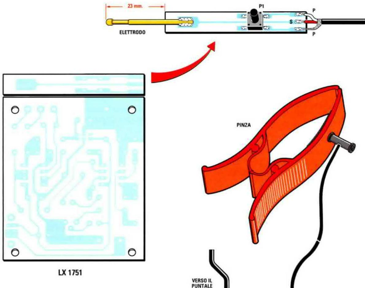
Fig.4 Per realizzare il puntale del cercapunti elettronico dovrete innanzitutto prelevare dallo stampato la sottile porzione visibile in alto e procedere a saldare, sul suo lato rame, l'elettrodo dorato in modo che fuoriesca di 23 mm, il pulsante P1 e il cavo schermato a 3 fili secondo la disposizione indicata nel disegno. Il tutto andrà quindi collocato all'interno del tubo del puntale seguendo la sequenza descritta nella pagina a lato.
