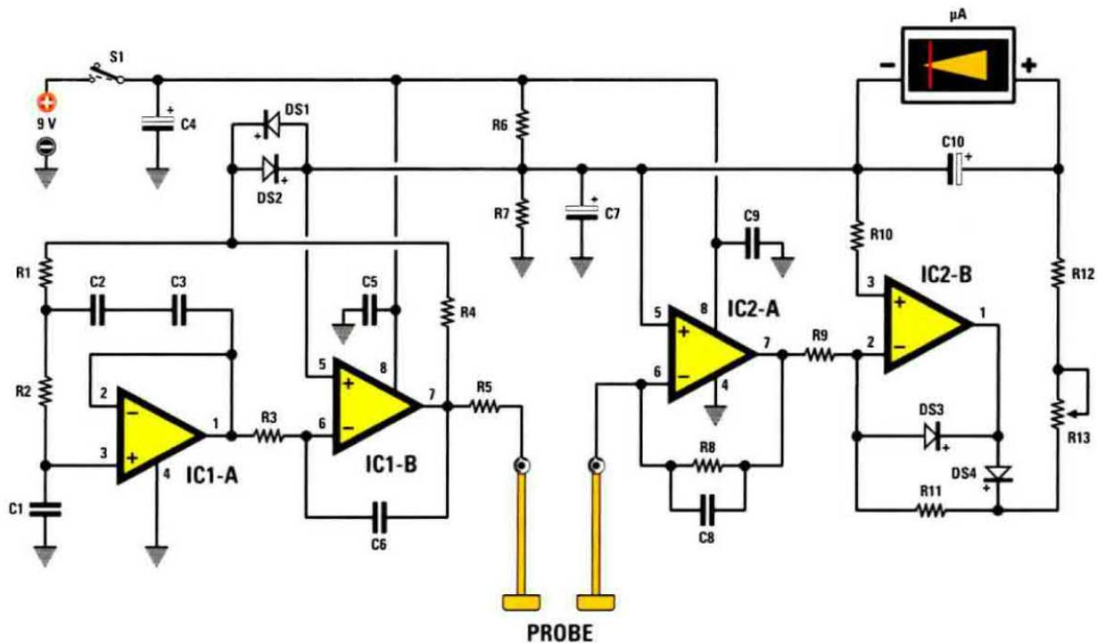
Fig.3 Schema elettrico dell'impedenzometro. Il segnale sinusoidale presente sul piedino 7 di IC1/B viene inviato al probe tramite la resistenza R5. L'interposizione della pelle tra i due elettrodi del probe determina una variazione del guadagno dell'amplificatore IC2/A, che si traduce in un maggiore o minore spostamento della lancetta del microamperometro.
