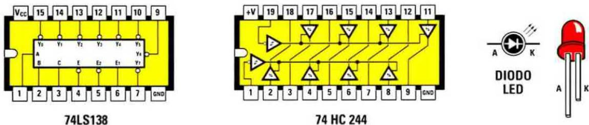
**Fig.15** Le connessioni degli integrati 74LS.138 e 74HC244 viste da sopra e con la tacca di riferimento a U rivolta a sinistra. Nei diodi led il terminale Anodo è più lungo del K.
