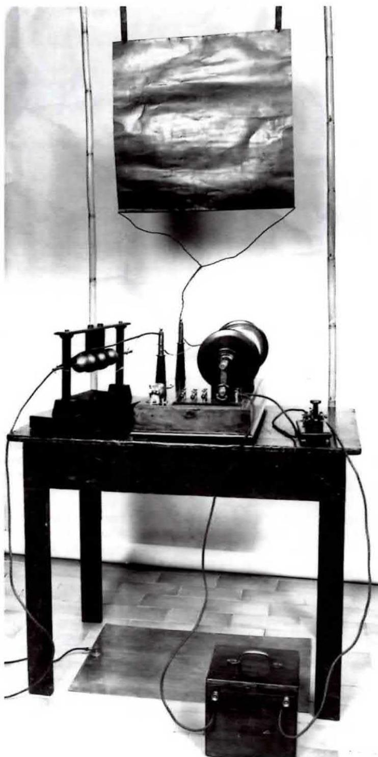
**L'apparecchio trasmettitore autocostruito da Marconi, e utilizzato nell'esperimento di trasmissione del 1895 a Villa Griffone. Sono chiaramente visibili le due lamiere metalliche che fungevano da antenna.**
