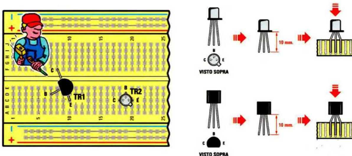
Fig.13 Cominceremo inserendo nella bassetta i due **transistor NPN** siglati **BC547** e **2N2222**. Dopo averli prelevati dal kit osservateli: come vedete sono provvisti di tre terminali corrispondenti rispettivamente alla **base (B)**, all'**emettitore (E)** e al **collettore (C)**. Per montarli correttamente nella bassetta dovrete aiutarvi con una pinzetta, inserendoli come indicato nel disegno.
