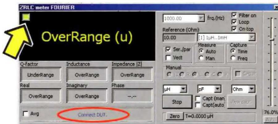
Ciò sta ad indicare che lo strumento ha provveduto ad aggiustare il livello della sinusoide che verrà applicata all'impedenza da misurare in funzione della portata precedentemente impostata. Una volta completata la calibrazione, vedrete comparire la scritta:
