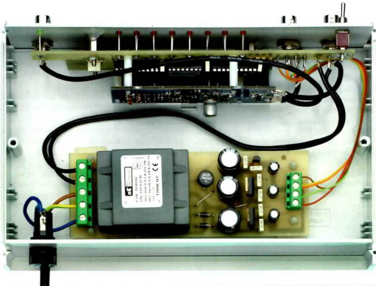
**Fig.24** Lo stadio di alimentazione LX.1749, il cui schema pratico di montaggio è riprodotto in fig.21, deve essere fissato sul piano del mobile con 4 distanziatori plastici con base autoadesiva. Dopo aver infilato i perni dei distanziatori nei fori dello stampato, dovete togliere dalle loro basi la carta che protegge l'adesivo, poi premete tutto lo stadio di alimentazione sul piano del mobile e in questo modo non si muoverà più.
