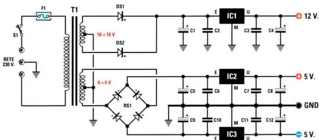
Fig.21 Schema elettrico dello stadio di alimentazione del Sintetizzatore.
