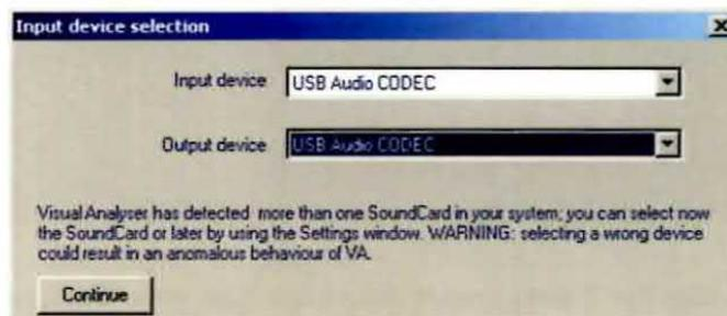
**Nota:** la procedura che avete appena eseguito serve a selezionare la **scheda audio (device)** che verrà utilizzata dalla porta USB del vostro pc per effettuare le comunicazioni in **ingresso (input)** e in **uscita (output)**. Se questa procedura non viene eseguita correttamente **non** è possibile eseguire la misura.
