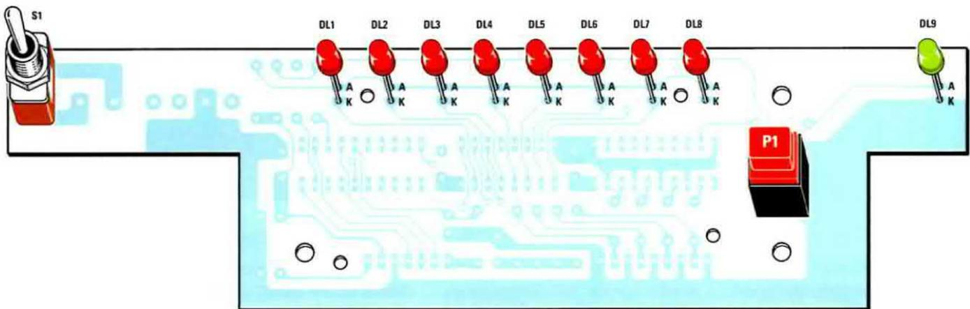
**Fig.14** Come saprete, il terminale più lungo dei diodi Led è l'Anodo (vedi fig.15) che va inserito nel foro indicato A. Poichè le teste di questi diodi Led devono fuoriuscire leggermente dal pannello frontale, prima di saldare i loro due terminali sulle piste in rame conviene fissare provvisoriamente il circuito stampato sui due distanziatori metallici presenti sul pannello stesso (vedi fig.16).
