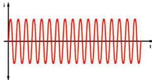
Fig.8 Per mantenere l'oscillazione del circuito in modo permanente è sufficiente utilizzare un componente attivo come un transistor il quale, fornendo continuamente energia al circuito, riesce a produrre un'onda perfettamente sinusoidale come quella rappresentata in figura.
