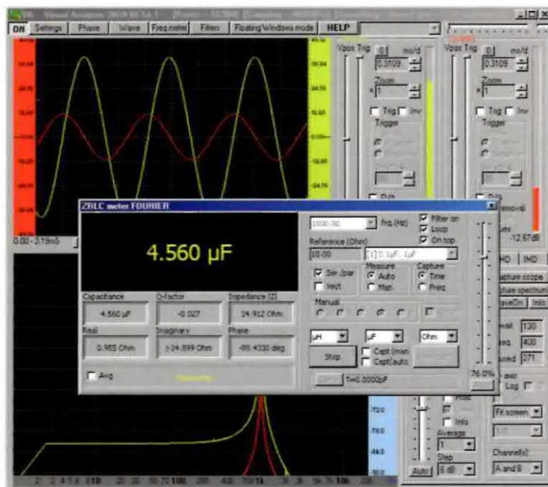
Come potete notare la misura ha fornito un valore di capacità di **4,56 microFarad**, che si discosta pochissimo dal valore nominale di **4,7 microFarad**.
