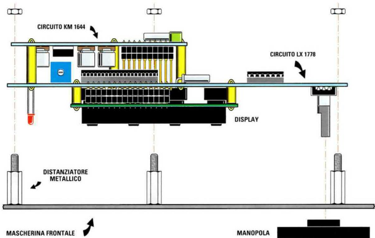
Fig.23 In questo disegno e nel successivo abbiamo illustrato la sequenza di fissaggio del "blocco" costituito dal KM1644 e dalla scheda LX.1778 sulla mascherina frontale del mobile destinato a contenere il nostro ricevitore.
