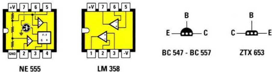
Fig.6 A partire da sinistra sono riprodotte le connessioni degli integrati NE555 e LM358 viste dall'alto e con la tacca di riferimento rivolta verso sinistra, del transistor BC547 e dell'equivalente BC557, e del transistor ZTX653 viste da sotto.
