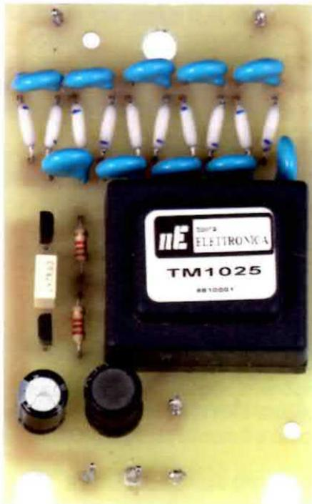
Fig.7 La foto del circuito stampato a montaggio ultimato.
