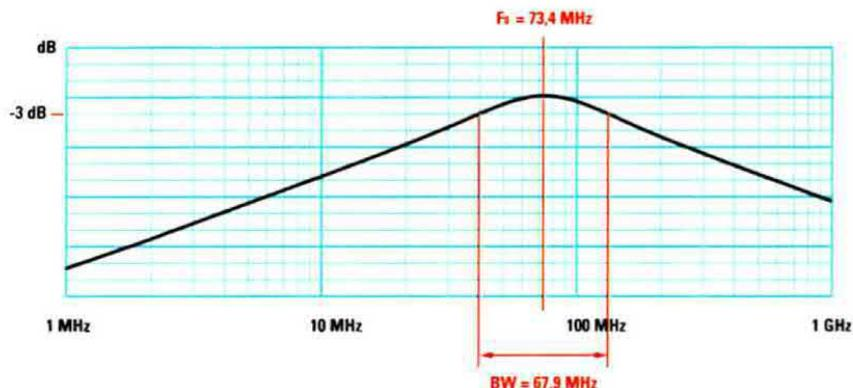
Fig.6 Come potete desumere dal grafico, la resistenza di uscita del generatore RS influenza il Q del circuito risonante.
