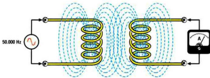
Fig.4 In aria, per aumentare il trasferimento di potenza e le dimensioni delle bobine occorre aumentare la frequenza del generatore.
