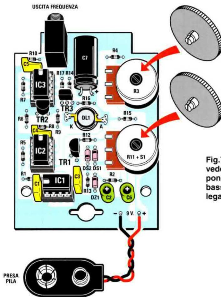
Fig.7 In questo disegno potete vedere la disposizione dei componenti sul circuito stampato. In basso è visibile la presa per il collegamento alla pila da 9 Volt.
