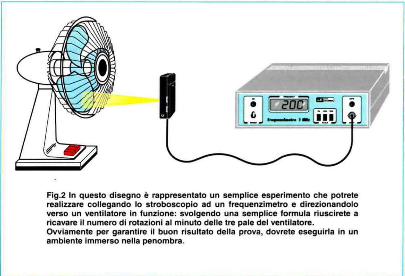
**Fig.2** In questo disegno è rappresentato un semplice esperimento che potrete realizzare collegando lo stroboscopio ad un frequenzimetro e direzionandolo verso un ventilatore in funzione: svolgendo una semplice formula riuscirete a ricavare il numero di rotazioni al minuto delle tre pale del ventilatore. Ovviamente per garantire il buon risultato della prova, dovrete eseguirla in un ambiente immerso nella penombra.
