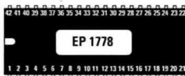
Fig.6 A sinistra le connessioni della Eprom EP1778 viste dall’alto e con la tacca di riferimento rivolta a sinistra.
