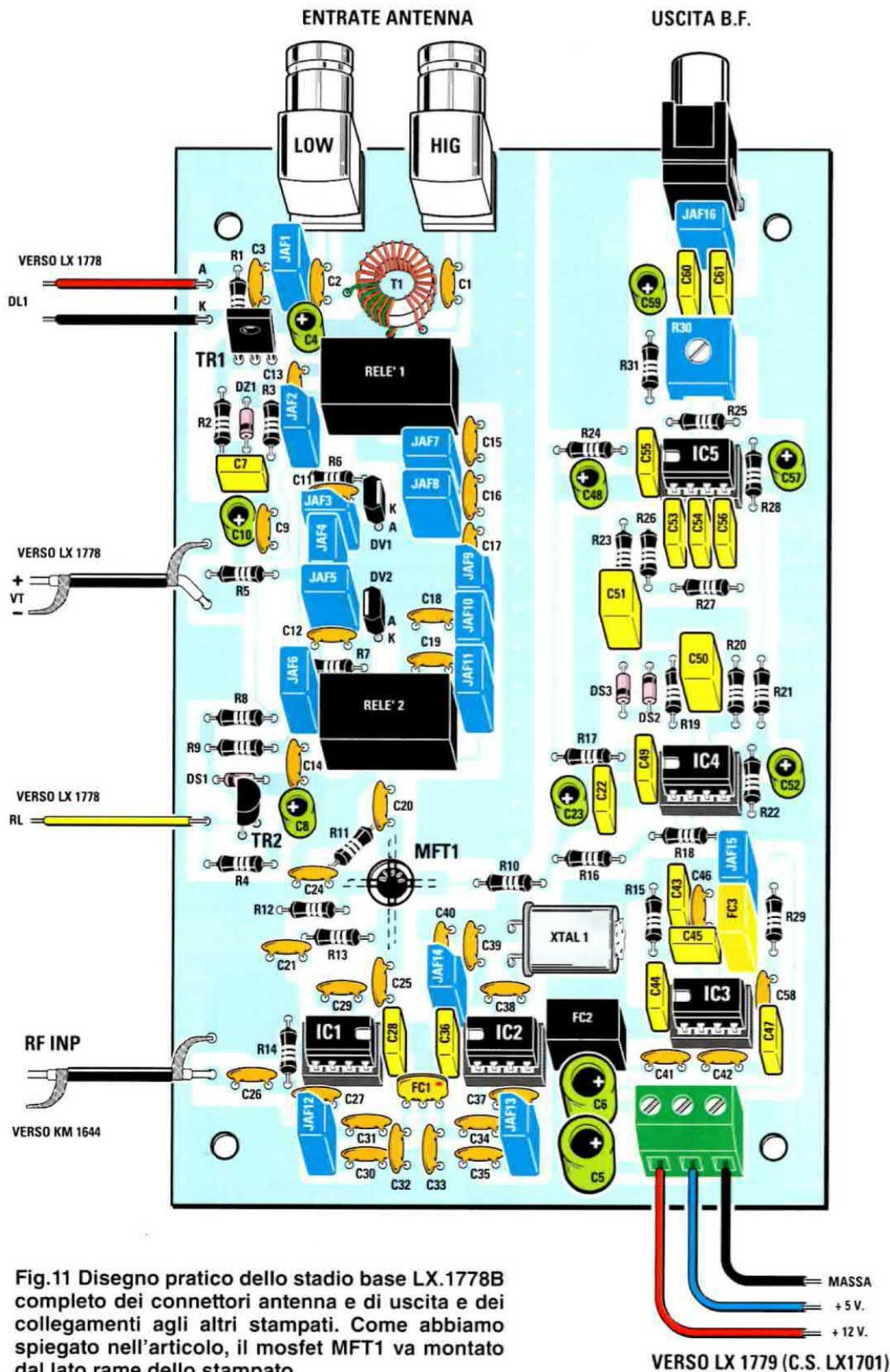
Fig.11 Disegno pratico dello stadio base LX.1778B completo dei connettori antenna e di uscita e dei collegamenti agli altri stampati. Come abbiamo spiegato nell'articolo, il mosfet MFT1 va montato dal lato rame dello stampato.
