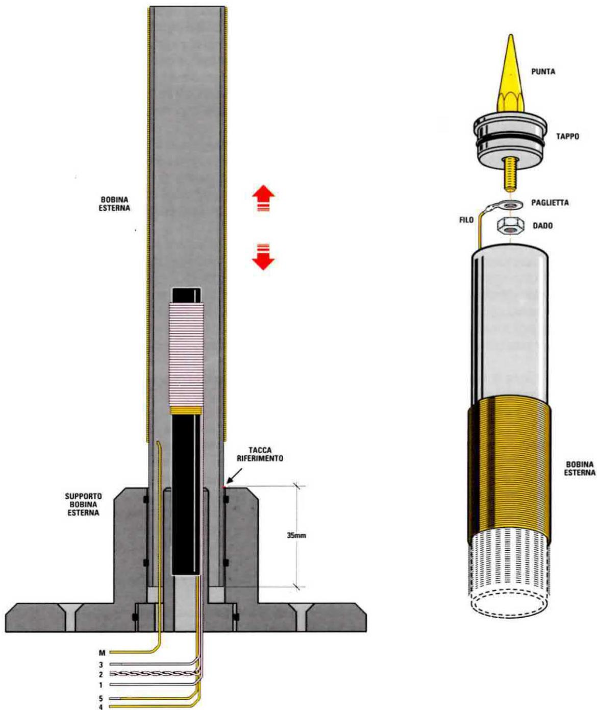
Fig.10 La fase successiva consiste nell'inserimento della bobina nel supporto esterno. La bobina andrà inserita fino alla linea tracciata precedentemente, che approssima la condizione di efficienza ottimale. Questa posizione andrà poi leggermente ritoccata durante la fase di taratura, inserendo oppure estraendo di qualche millimetro la bobina dal suo supporto. L'ultima operazione da eseguire è l'assemblaggio della punta e la saldatura del filo corrispondente al terminale superiore della bobina.
