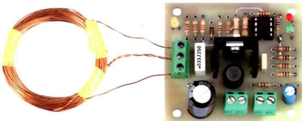
**Fig.12** In questa foto abbiamo riprodotto lo schema pratico dello stadio ricevitore che abbiamo realizzato insieme allo stadio trasmettitore riprodotto in fig.11 per realizzare tutte le nostre prove di laboratorio.
