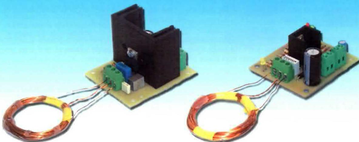
Fig.1 Ecco come si presentano a montaggio ultimato i circuiti del trasmettitore e del ricevitore che costituiscono il nostro caricabatteria.
