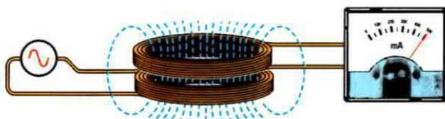
Fig 6 Avvicinando le bobine l'una all'altra come esemplificato nel disegno, si ottiene la massima erogazione di corrente.
