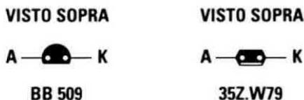
**Fig.8** Connessioni viste da sopra e viste da sotto del diodo varicap **BB509** e del suo equivalente **35Z.W79**.
