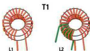
Fig.13 Per realizzare il trasformatore T1 dovete autocostruirvi la bobina L1 avvolgendo 22 spire di filo smaltato da distribuire sull'intera circonferenza del nucleo in ferrite e la bobina L2 avvolgendo altre 5 spire.
