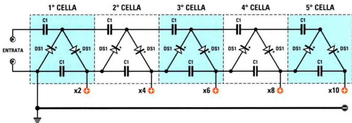
Fig.5 Per ottenere tensioni molto elevate potete utilizzare questo schema, composto da più celle duplicatrici. Più alta sarà la frequenza della tensione alternata da raddrizzare e da duplicare e minore risulterà la capacità dei condensatori di accoppiamento.
