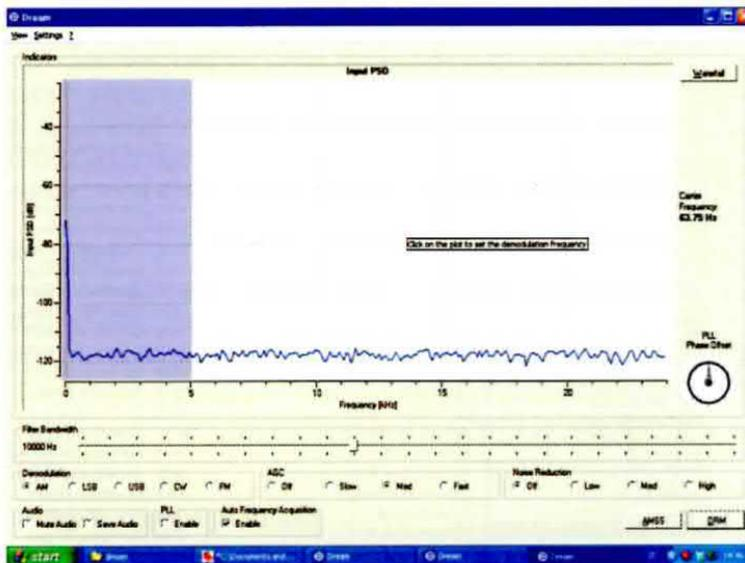
Fig.32 Ovviamente, non essendoci nessun segnale applicato all'ingresso della scheda audio, lo spettro apparirà piatto. Al centro dello schermo si vede il puntatore del mouse che serve a spostare la sintonia (linea tratteggiata rossa).
