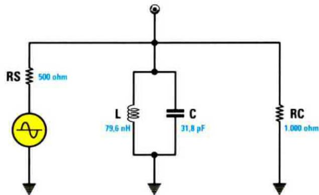
Proseguiamo l'esempio di fig.11, evidenziando come, una volta conosciuti i valori di  $X_L$  e  $X_C$ , sia semplice calcolare i valori di  $L$  e di  $C$  in funzione della frequenza di lavoro usando la formula sotto riportata.
