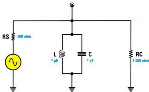
Fig.11 Con questo esempio evidenziamo come sia possibile calcolare i componenti L/C in modo da ottenere un circuito risonante con una determinata larghezza di banda in funzione dei valori RS e RC. L'esempio prosegue nella pagina successiva.
