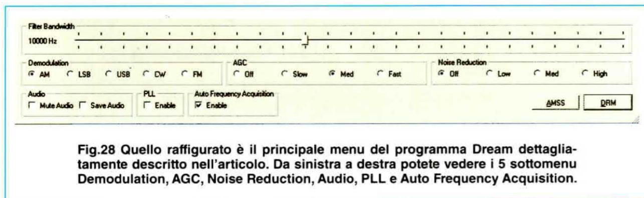
**Fig.28** Quello raffigurato è il principale menu del programma Dream dettagliatamente descritto nell'articolo. Da sinistra a destra potete vedere i 5 sottomenu Demodulation, AGC, Noise Reduction, Audio, PLL e Auto Frequency Acquisition.
