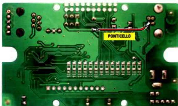
Fig.4 Foto della scheda USB vista dal retro, dal lato cioè sul quale dovrete saldare il ponticello necessario per trasferire a tutti i componenti l'alimentazione dei 5 Volt provenienti dalla presa USB del computer.
