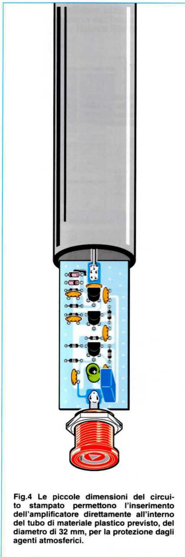
**Fig.4** Le piccole dimensioni del circuito stampato permettono l'inserimento dell'amplificatore direttamente all'interno del tubo di materiale plastico previsto, del diametro di 32 mm, per la protezione dagli agenti atmosferici.
