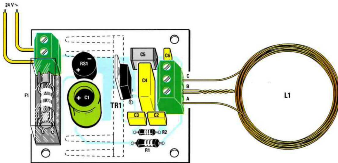
Fig.9 Schema pratico di montaggio della scheda del trasmettitore. Prima di montare il transistor TR1 sullo stampato, dovrete fissarlo sull'aletta di raffreddamento di cui abbiamo tratteggiato la sagoma nel disegno.
