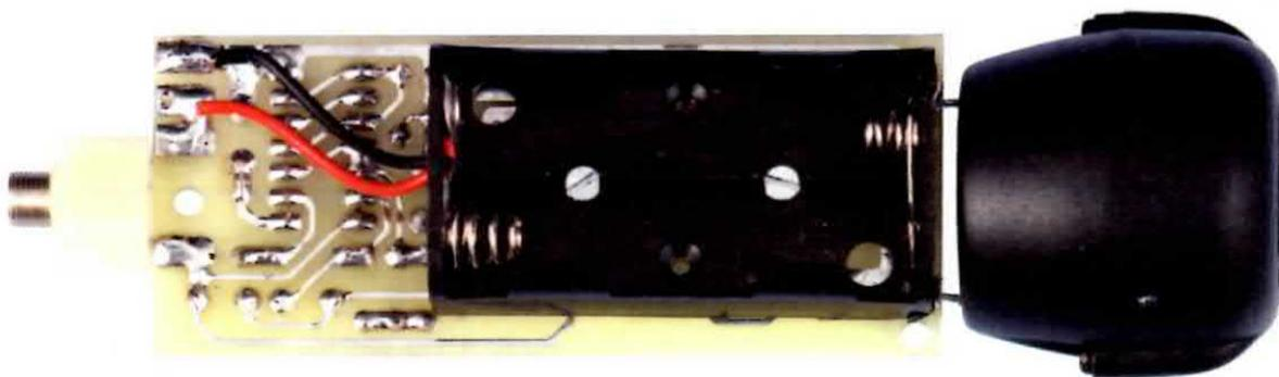
Fig.8 Foto del montaggio visto dal lato sul quale è fissato il portapile.
