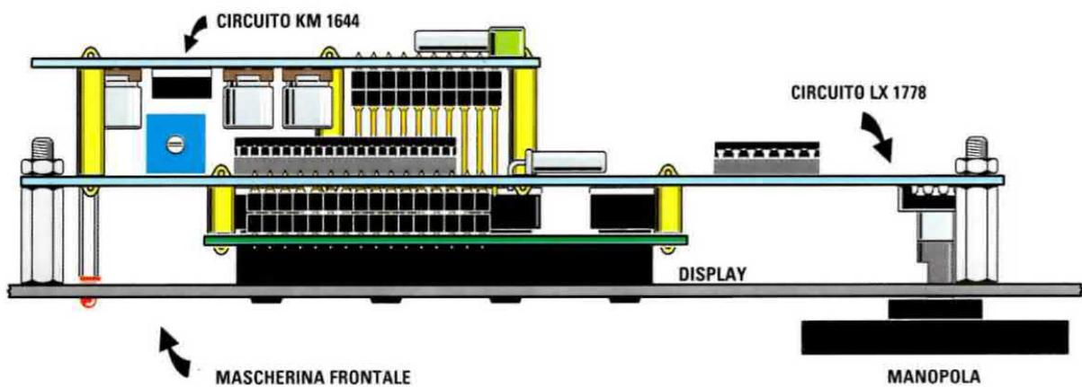
Fig.24 In questo disegno è raffigurato dall'alto il risultato dell'operazione di assemblaggio del KM1644 con l'LX.1778 e la mascherina frontale del mobile.
