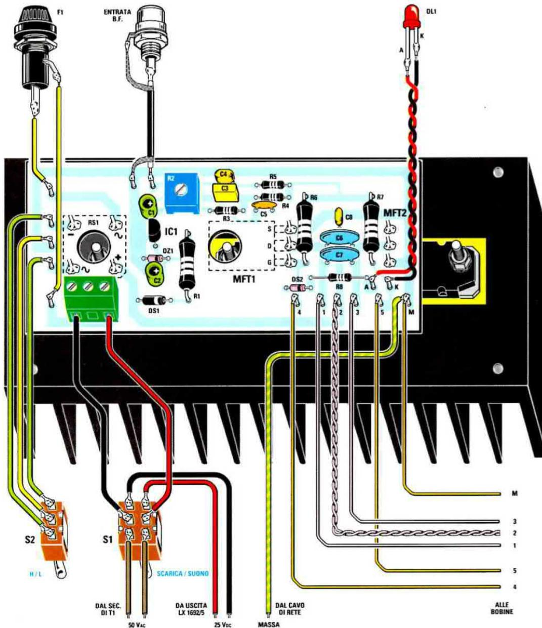
**Fig.7** Fate molta attenzione a rispettare la polarità dei fili di colore rosso e nero che collegano il deviatore S1 con la morsetteria e con la scheda LX.1692/5. In caso contrario potreste danneggiare il circuito. Collegate inoltre il filo di massa come indicato in figura.
