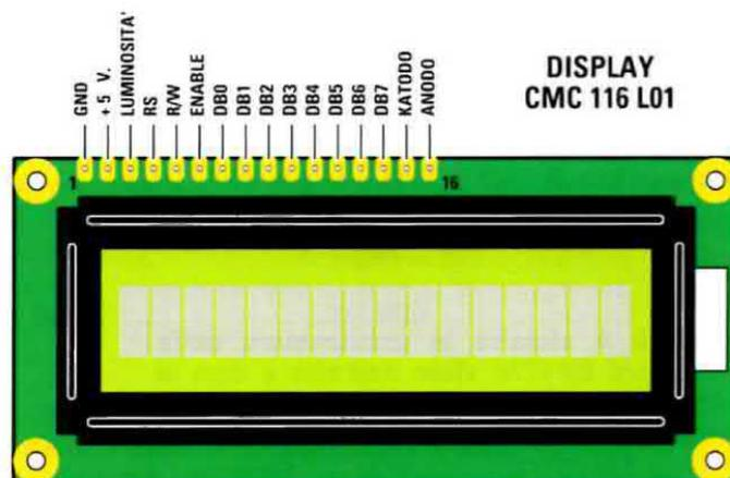
Fig.4 In figura potete vedere la piedinatura del display LCD siglato CMC116L01 che abbiamo impiegato nella realizzazione del progetto.
