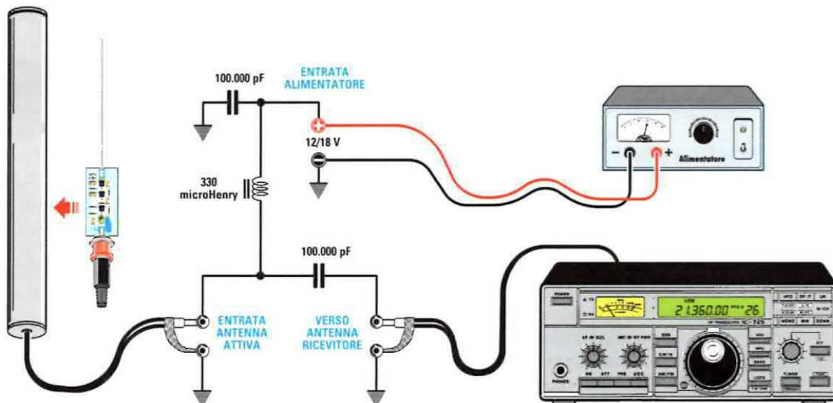
**Fig.1** In questo disegno potete vedere il circuito disaccoppiatore da costruire nel caso in cui l'antenna attiva venga utilizzata su ricevitori sprovvisti della necessaria tensione continua sul connettore di ingresso antenna.
