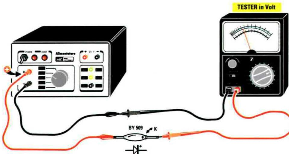
Fig.4 Per individuare il terminale + del diodo BY509 potete ricorrere ad un normale tester e ad un alimentatore o ad una pila a 9 V. Quando il tester legge una tensione positiva contrassegnate questo lato del corpo corrispondente al K.
