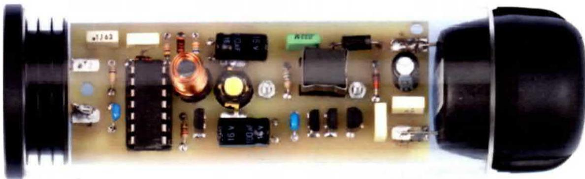
Fig.9 Ecco come si presenta il circuito della sirena una volta inserito all'interno del tubo in plastica trasparente utilizzato come contenitore per permettere la vista della luce flash emessa dal diodo led.
