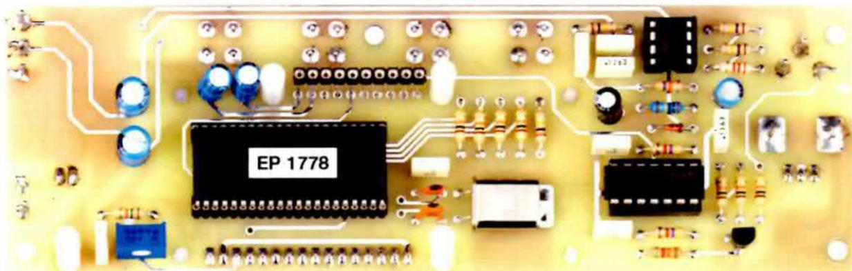
**Fig.16** Foto dello stadio CPU siglato LX.1778 visto dal lato componenti sul quale andrà innestata la scheda in SMD siglata KM1644 (vedi figg.17-18). Dal lato opposto andranno invece montati il display LCD, i quattro pulsanti, la manopola ed il diodo led come evidenziato in fig.21.
