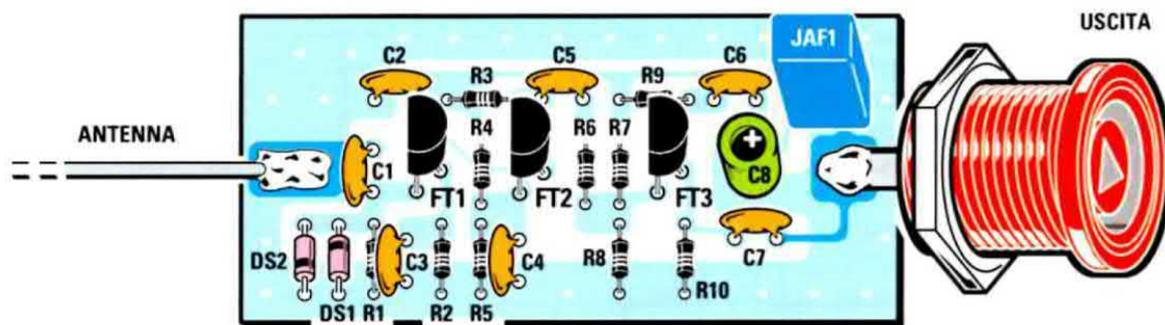
Fig.3 Schema pratico di montaggio dell'LX.1777. La lunghezza dello stilo antenna che in questo disegno è appena accennato, può essere anche superiore a 1 metro da noi suggerito. Ovviamente anche il relativo tubo di protezione dovrà avere una lunghezza adatta a contenerlo insieme al circuito amplificatore. Sotto, foto del circuito a montaggio ultimato.
