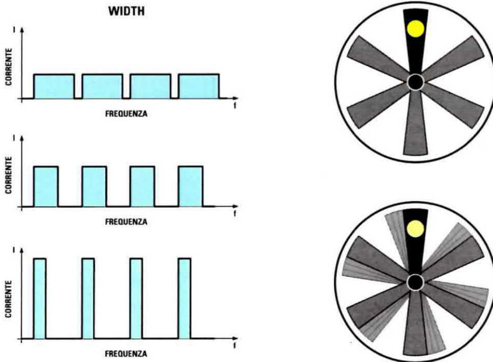
**Fig.3** Come potete desumere dai 3 grafici riprodotti a sinistra, la corrente del diodo led aumenta se la larghezza dell'impulso si riduce e viceversa e ciò per compensare la normale perdita di luminosità man mano che l'impulso diventa più stretto. La variazione della larghezza dell'impulso è necessaria per eliminare il fastidioso effetto "scia" riprodotto nell'immagine di destra, in quanto l'oggetto da osservare viene illuminato soltanto per un tempo brevissimo.
