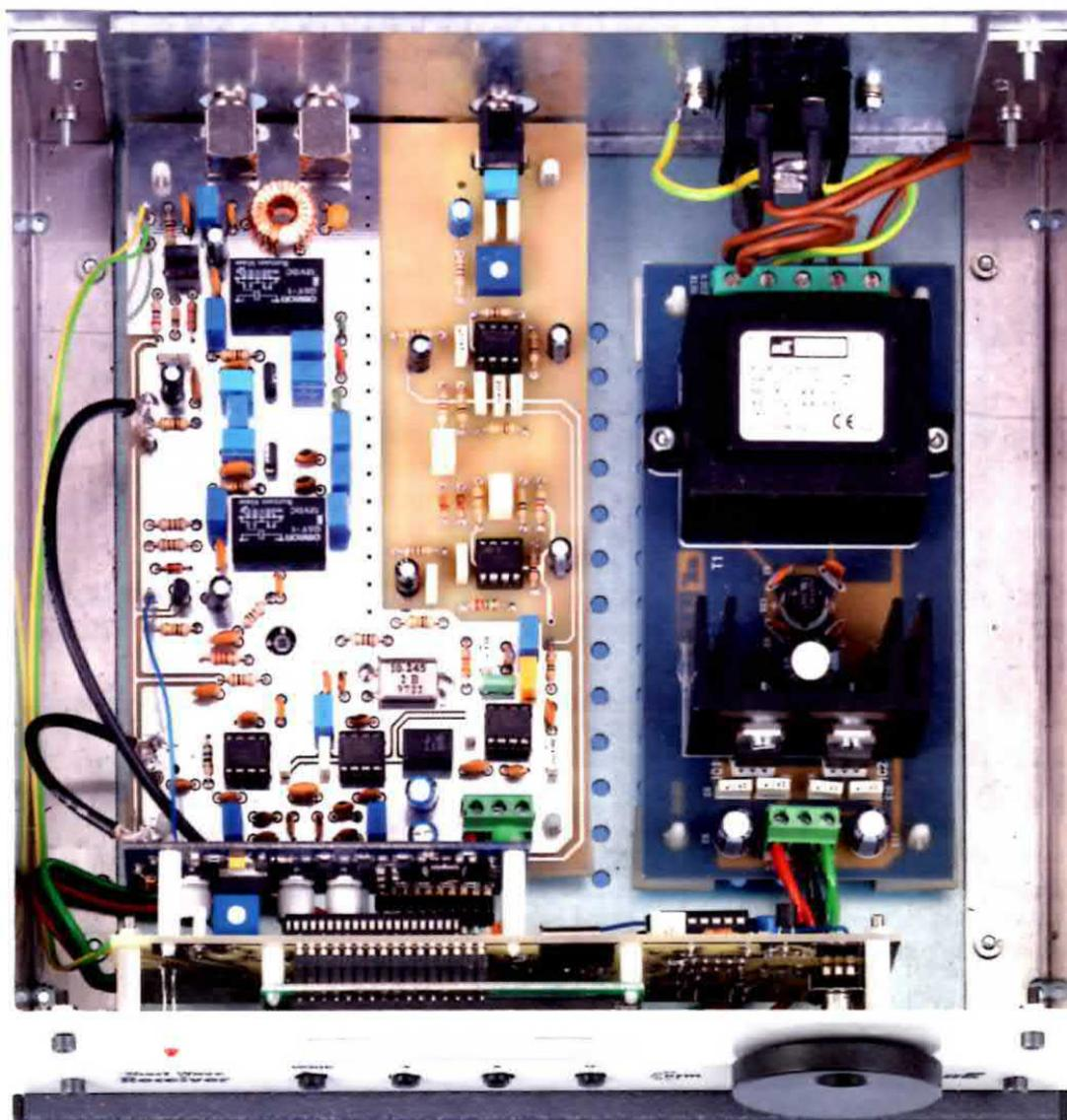
**Fig.26** Foto del progetto del nostro ricevitore a montaggio ultimato e inserito all'interno del mobile. Come potete notare dalla mascherina posteriore del mobile fuoriescono le due prese BNC per l'entrata antenna e la presa uscita BF collegate alla scheda base LX.1778B oltre alla presa di rete e all'interruttore S1 collegate invece alla scheda di alimentazione LX.1779.
