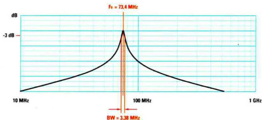
**Fig.7** Rispetto alla fig.6 dove la **RS** risultava da **50 ohm**, aumentandone il valore a **1.000 ohm** possiamo notare una maggiore selettività.
