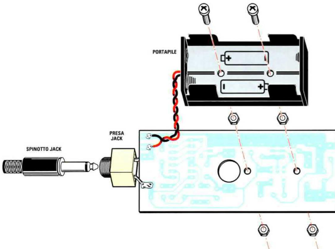
Fig.6 In questo disegno è rappresentato il circuito stampato della sirena visto dal retro, dal lato cioè sul quale andrà fissato il portapile destinato ad accogliere due pile ministilo da 1,5 Volt ciascuna per la sua alimentazione.
