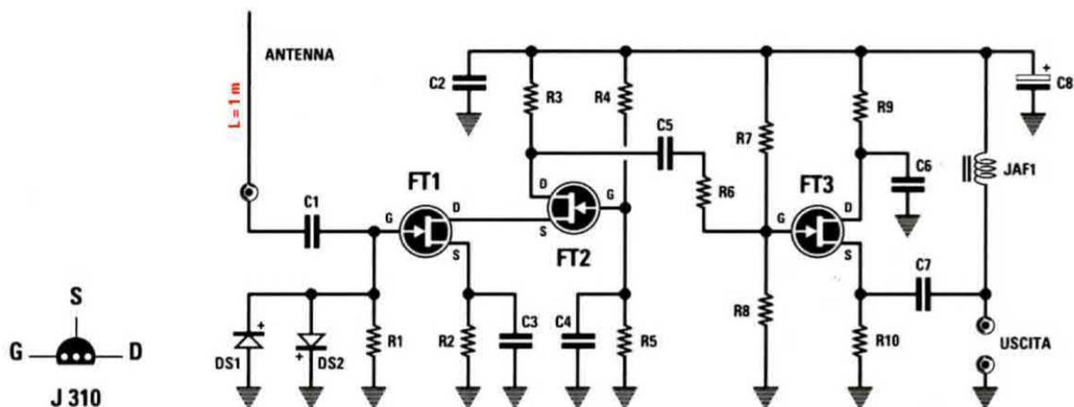
Fig.2 Schema elettrico dell'antenna attiva per onde corte LX.1777. Tutti i fet utilizzati per la sua realizzazione sono dei J310. A sinistra potete vedere le relative connessioni viste dal lato del corpo da cui fuoriescono i terminali G-S-D.
