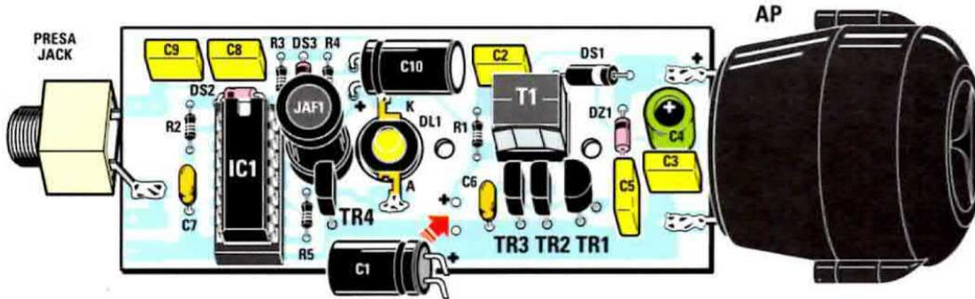
Fig.5 Disegno dello schema pratico di montaggio del circuito. Come potete notare, il diodo led da 1 Watt per SMD (codice =DL4.1) va collocato al centro del circuito stampato avendo l'accortezza di rivolgere i terminali catodo (K) e anodo (A) rispettivamente verso l'alto e verso il basso. Attenzione a rispettare la polarità +/- dei terminali della sirena.
