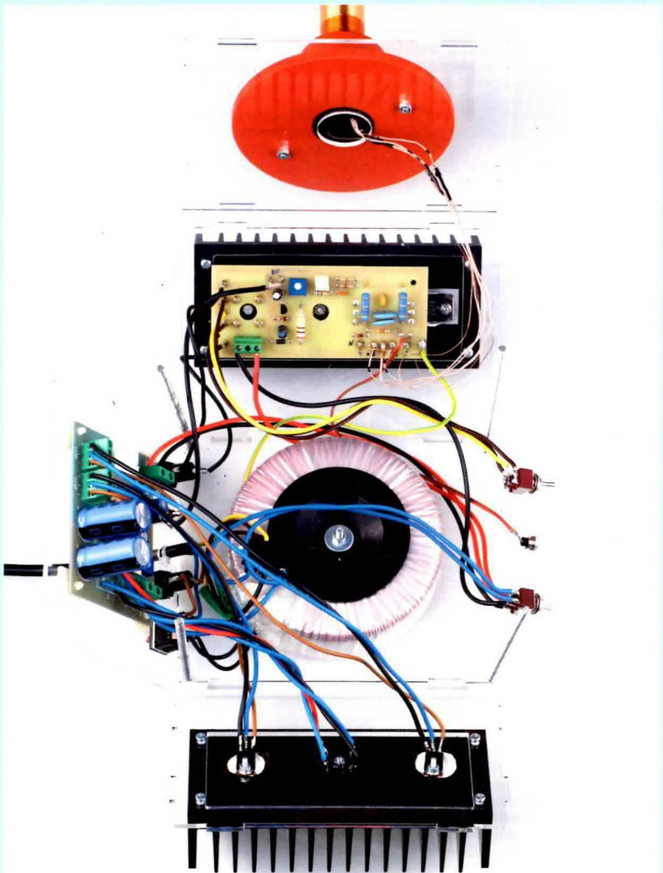
Fig.12 in fotografia è rappresentato il Tesla a montaggio ultimato. Prima di chiudere il mobile occorre procedere alla taratura della corrente di polarizzazione dei Mosfet. Accertatevi inoltre di avere ruotato al massimo in senso orario il potenziometro R10 posto sulla scheda LX.1692/5.
