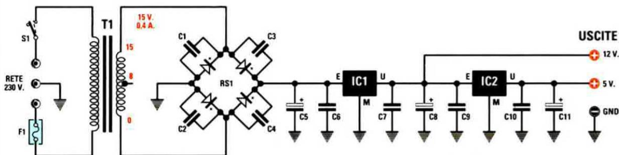
Fig.9 Schema elettrico dello stadio di alimentazione che fornisce le tensioni stabilizzate di 12 e 5 Volt. A destra, le connessioni dei due integrati regolatori L.7812 e L.7805 viste frontalmente.
