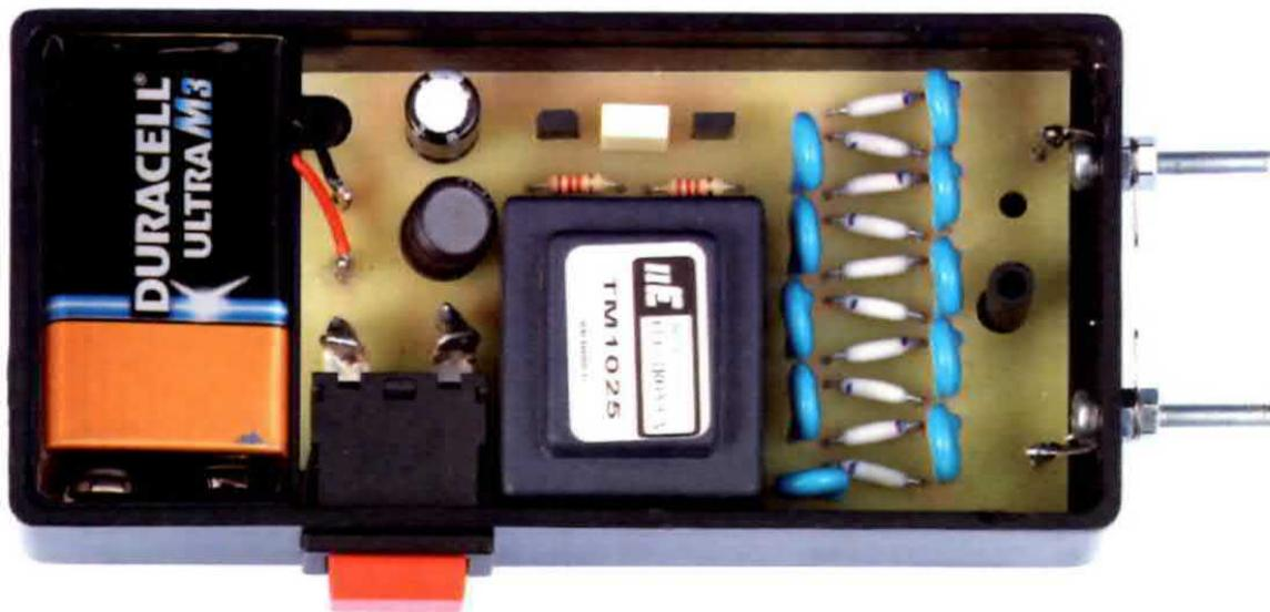
**Fig.8** Ecco come si presenta il circuito del dissuasore elettronico LX.1775 una volta inserito all'interno del mobile. A sinistra potete notare la pila a 9 Volt inserita nel vano appositamente predisposto.
