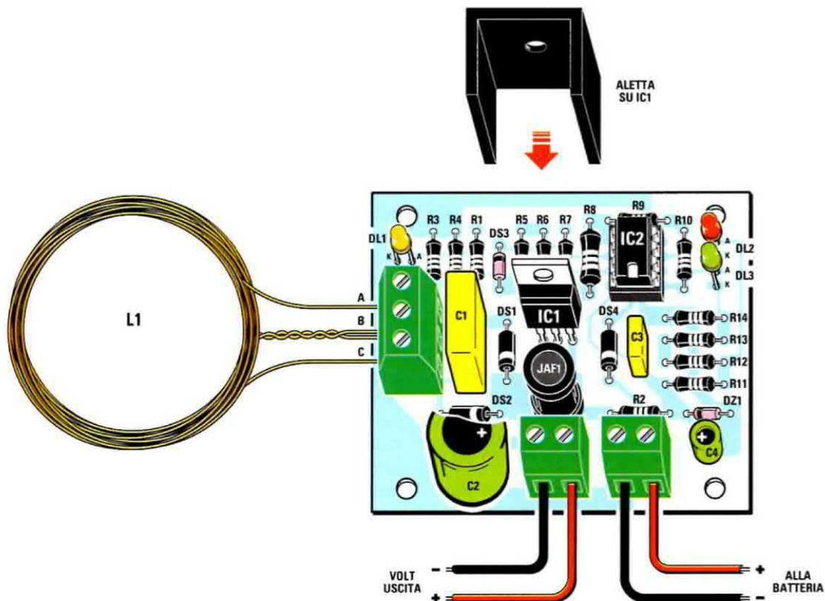
Fig.10 Schema pratico di montaggio della scheda del ricevitore. In questo caso, dovrete fissare l'integrato IC1 sull'aletta di raffreddamento prima di saldare i terminali nei fori predisposti al centro del circuito stampato.
