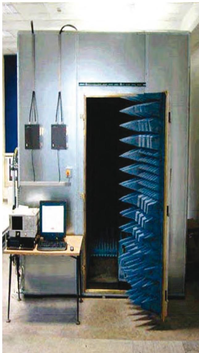
Fig.3 - Vista anteriore camera schermata e apparecchiature di misura.
