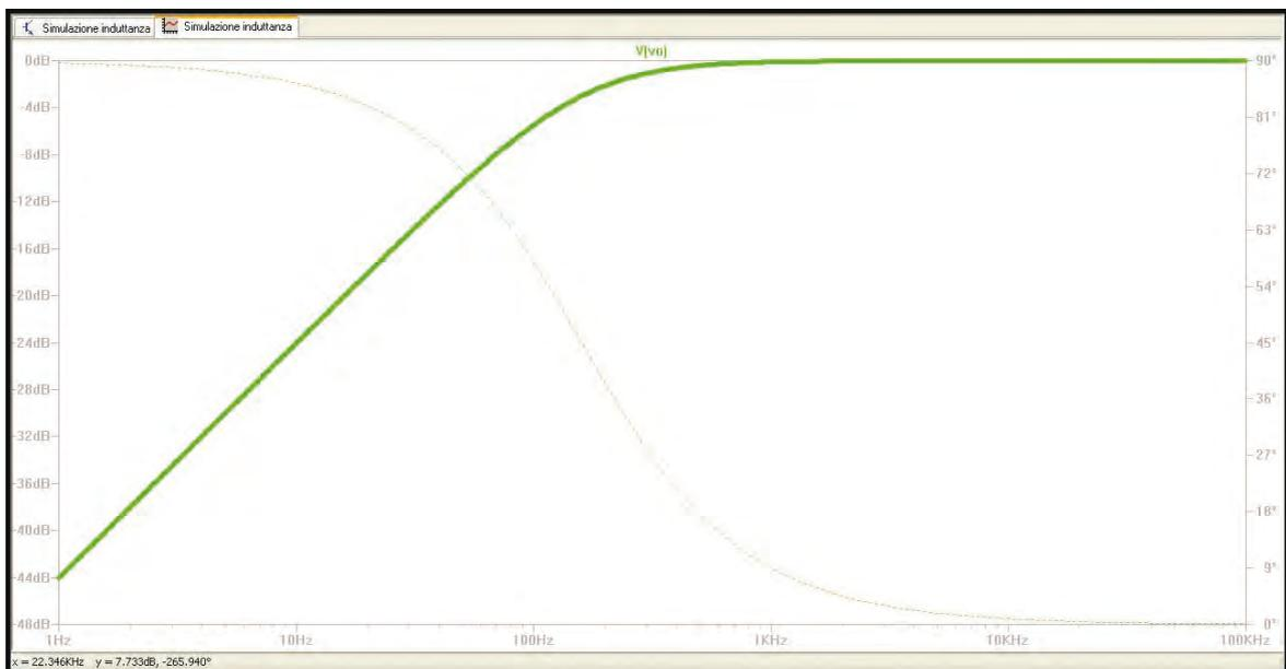
Fig.10 Risposta in frequenza con  $C1 = 1 \mu\text{F}$
