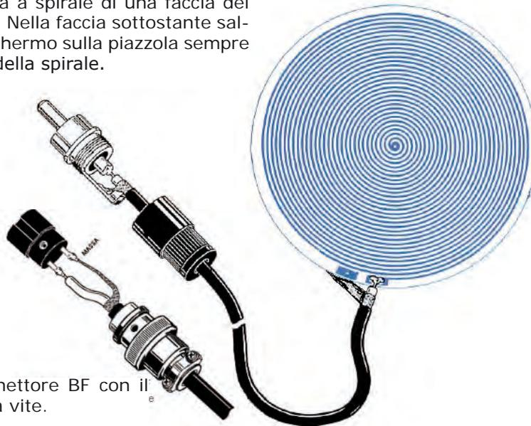
Sostituire il connettore BF con il connettore tipo a vite.
