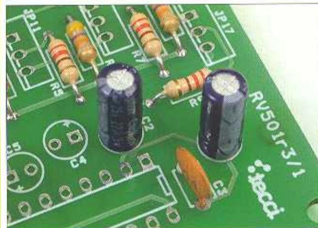
**7** Infine, salderemo un ultimo condensatore elettrolitico da 22  $\mu\text{F}$ , che sarà inserito in C2. Seguiremo lo stesso procedimento spiegato per il resto dei condensatori elettrolitici che abbiamo già montato; fate molta attenzione alla polarità! Una volta saldati tutti i condensatori, taglieremo la parte restante dei reofori utilizzando un tronchesino o delle forbici.
