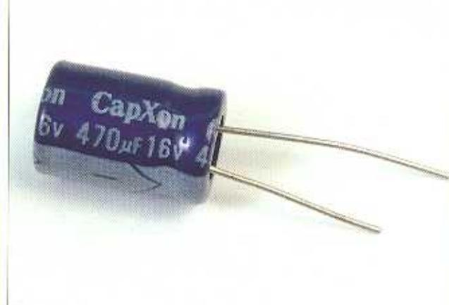
**2** Nell'immagine è mostrato il primo dei quattro condensatori elettrolitici che dobbiamo saldare. Questi condensatori hanno polarità, quindi è importante sia montarli nella posizione corretta della scheda che inserirli con l'orientamento adeguato. Il terminale negativo del condensatore è quello con il piedino più corto, inoltre il suo lato è segnato con una striscia bianca e con il simbolo "meno".
