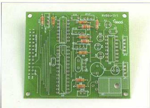
**8** Questo è l'aspetto finale che presenta la scheda con le otto resistenze saldate. Dobbiamo verificare di aver inserito e saldato le resistenze al loro posto corretto. Dobbiamo inoltre verificare che le saldature siano brillanti e a forma di cono, appoggiato sulla superficie della scheda, per assicurare una buona conduzione del circuito elettronico.
