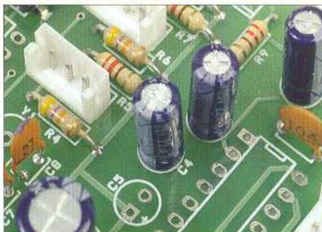
**8** Infine dobbiamo saldare un condensatore elettrolitico da 22  $\mu\text{F}$  in C4. Questo condensatore è dotato di polarità, nella serigrafia della scheda è indicato con un segno "+" dove bisogna inserire il terminale positivo del condensatore. Sul contenitore del condensatore si segnala con una striscia bianca e con il segno "-" il terminale negativo.
