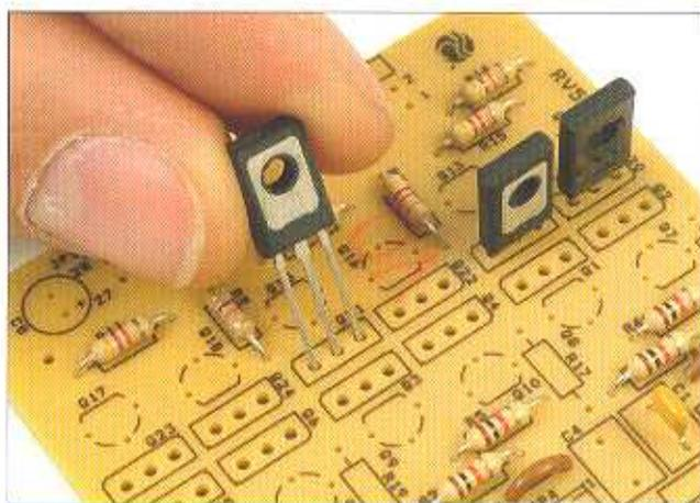
**1** Per prima cosa salderemo due transistor modello BD135. Li inseriremo in Q21. È importante montare i transistor con il corretto orientamento, come mostrato nell'immagine, perché sono componenti dotati di polarità.
