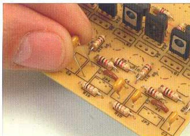
**1** Salderemo due condensatori ceramici da 470 nF nelle posizioni C3 e C4 della scheda di potenza. I condensatori di tipo ceramico non hanno polarità, quindi è indifferente il verso di inserzione che si utilizza.
