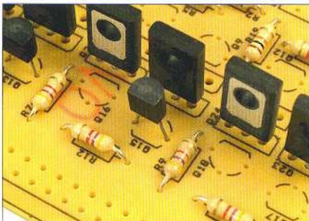
**3** Salderemo ora due transistor modello BC548. Essi, insieme ai transistor BD135, costituiscono un transistor tipo Darlington. Il primo transistor verrà montato in Q15 con il verso di inserzione mostrato nell'immagine. Dopo averlo saldato taglieremo la parte di reoforo in eccesso.
