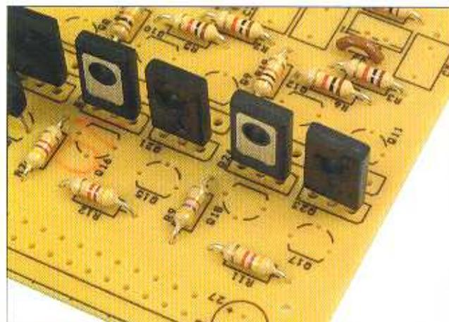
**2** Il secondo transistor BD135 lo monteremo nella posizione Q24, con l'orientamento mostrato nell'immagine. Dopo aver saldato il transistor dobbiamo utilizzare un paio di forbici o un tronchesino per eliminare la parte in eccesso dei reofori, lasciando una saldatura a forma di cono.
