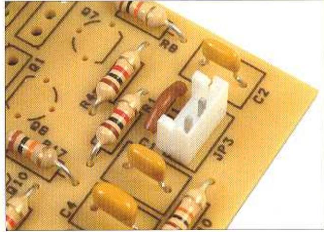
**6** Ora monteremo un connettore maschio, dritto, da due pin, e lo inseriremo nella posizione JP3 della scheda. È importante che il connettore sia orientato come indica la figura.
