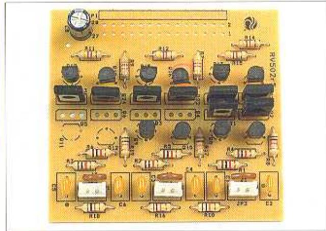
**8** Vista frontale della scheda di potenza con la maggioranza di componenti già montati. Mancano solamente alcuni transistor e il connettore principale per la connessione della scheda di potenza alla scheda di interfaccia.
