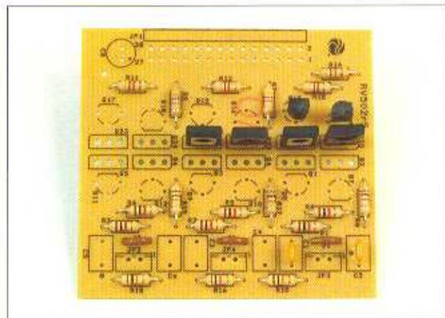
**8** Nell'immagine possiamo vedere la scheda di potenza, con i componenti montati e saldati sino a questo momento. Dobbiamo verificare che tutto sia nella posizione corretta e che i transistor siano montati con il verso di inserzione appropriato.
