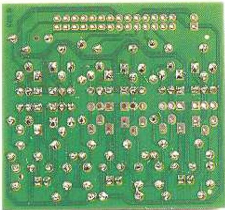
**7** Vista della scheda di potenza dalla parte posteriore, in cui si possono apprezzare tutte le saldature realizzate fino a questo momento. Conviene controllare la scheda da questo lato per verificare che le saldature brillino alla luce e che siano correttamente appoggiate sulla superficie della scheda.
