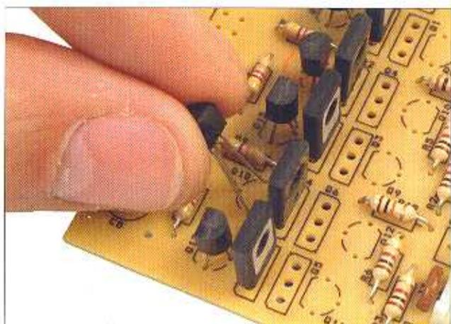
**4** Adesso monteremo l'ultimo transistor modello BC548 di cui dispone la scheda di potenza. Sarà inserito in Q18 con lo stesso orientamento mostrato nell'immagine. Deve rimanere sollevato dalla superficie di alcuni millimetri, come tutti i transistor.
