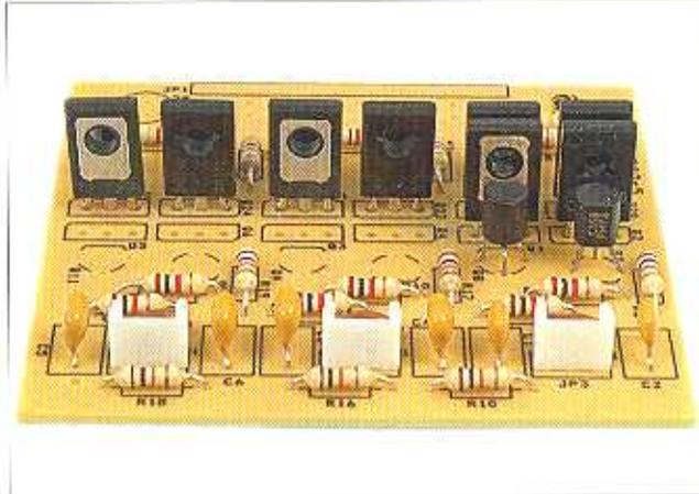
**6** Nell'immagine è riportata una vista della scheda di potenza, leggermente inclinata per poter mostrare il profilo dei componenti montati. Tutti debbono rimanere a filo della scheda, eccetto i transistor, che devono rimanere sollevati dalla superficie.
