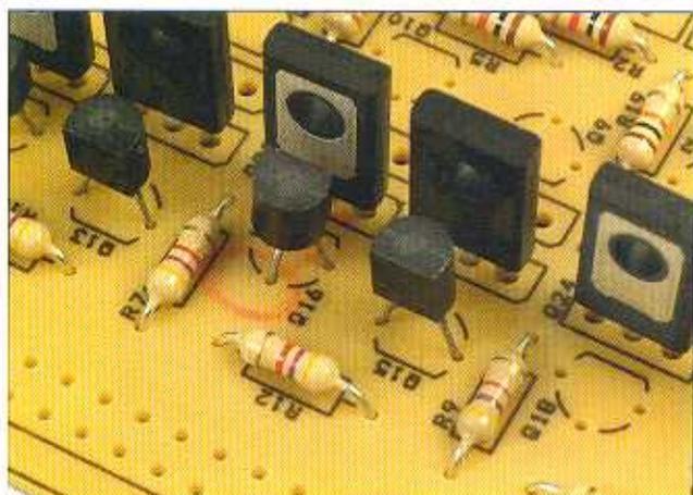
**4** Ora monteremo l'altro transistor modello BC548 nella posizione Q16 della scheda rispettando il verso di inserzione indicato dalla serigrafia. Così come per il resto dei transistor BD135, dobbiamo inserire il modello BC548 in modo che rimanga qualche millimetro sollevato dalla superficie.
