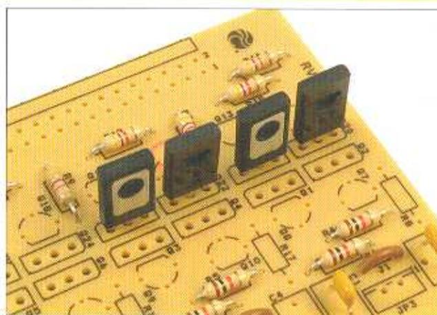
**2** Il successivo transistor BD135 si monta in Q22. Deve avere lo stesso orientamento di quello mostrato nell'immagine che è indicato nella scheda tramite la serigrafia. I transistor devono rimanere qualche millimetro sollevati dalla superficie, non completamente appoggiati ad essa.
