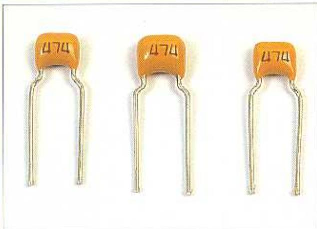
**5** Dobbiamo conservare i condensatori ceramici da 470 nF forniti con questo fascicolo. Questi condensatori verranno saldati ai due poli dei motori, quando faremo il montaggio dei medesimi. Questi condensatori filtreranno i rumori indotti dai motori verso le schede elettroniche.
