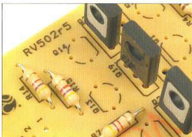
**3** Saldiamo ora due transistor modello BC548. Sulla scheda è indicato il verso di inserzione del transistor mediante un disegno a forma di mezza luna. Questa è la forma che ha un transistor BC548 visto da sopra. Al momento dell'inserzione dovremo fare in modo che la forma del transistor coincida con quella disegnata sulla scheda.
