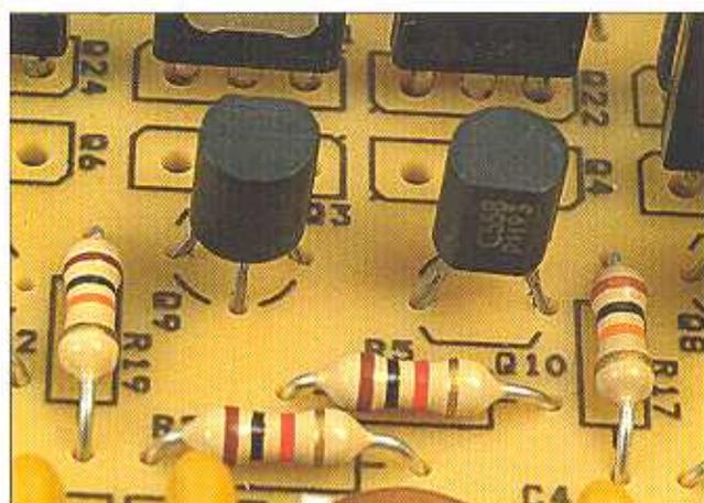
**3** Il secondo transistor modello BC558 verrà saldato nella posizione Q10 della scheda di potenza, rispettando sempre il corretto verso di inserzione indicato dalla serigrafia. I due transistor devono rimanere orientati secondo quanto mostra l'immagine.
