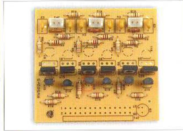
**8** Vista frontale della scheda di potenza con i vari componenti, resistenze, transistor, condensatori e connettori saldati sino a questo momento. Dobbiamo verificare che tutto sia montato in modo corretto.
