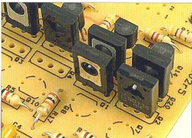
**3** Il secondo transistor BD136 lo monteremo e salderemo in Q2, con il verso di inserzione che vediamo nella figura. I transistor devono sempre rimanere sollevati di qualche millimetro dalla superficie, per garantire una buona dissipazione.
