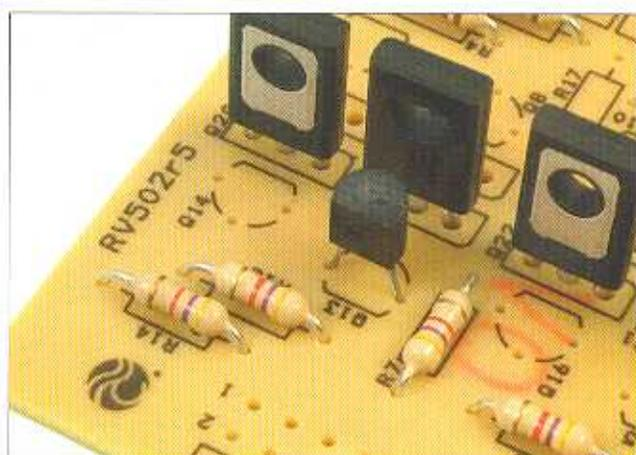
**4** Il primo transistor BC548 viene inserito in Q13. Il verso di inserzione deve essere quello mostrato dall'immagine. Così come i transistor BD135, il transistor non deve essere completamente poggiato sulla scheda ma sollevato di qualche millimetro dalla superficie.
