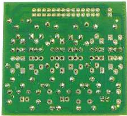
**7** Questo è il lato anteriore della scheda di potenza. In essa possiamo vedere le saldature realizzate sino a questo momento. Tutte devono essere a forma di cono, avere un aspetto brillante e riflettere la luce. Non devono avere la forma di bolla e devono essere ben appoggiate sulla superficie della scheda.
