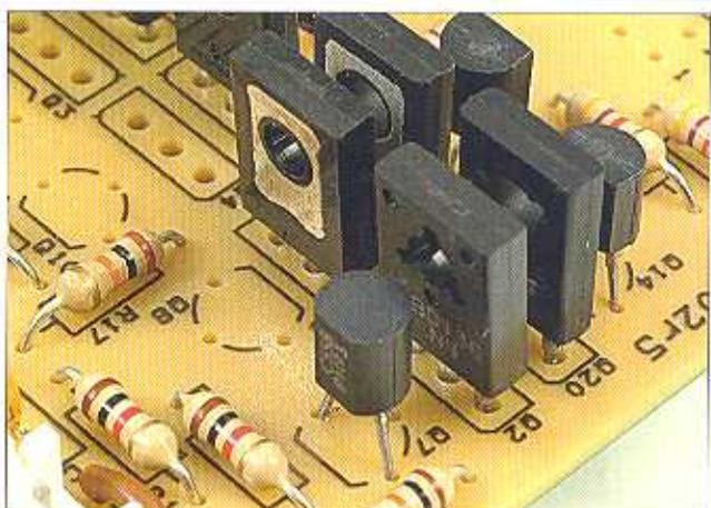
**4** Ora salderemo i transistor BC558. Il primo di questi verrà inserito e montato nella posizione Q7 della scheda. Bisogna rispettare il verso di inserzione indicato dalla serigrafia, così come abbiamo fatto con i transistor modello BC548 già montati.
