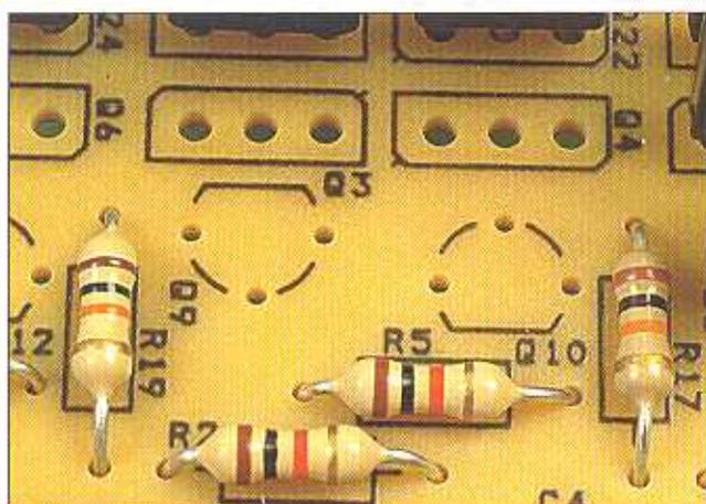
**1** Salderemo due transistor PNP modello BC558 nelle posizioni Q9 e Q10 della scheda di potenza. La serigrafia della scheda indica, mediante un disegno a forma di mezza luna, il verso di inserzione che devono avere i transistor.
