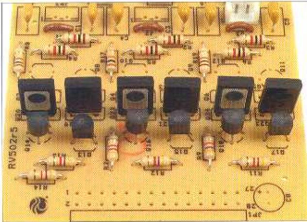
**5** In questa immagine possiamo vedere il dettaglio della zona della scheda dove abbiamo montato e saldato tutti i transistor NPN di cui è composta la scheda di potenza. Ogni transistor deve trovarsi nel posto che gli compete e con il verso di inserzione adeguato, altrimenti la scheda non funzionerà.
