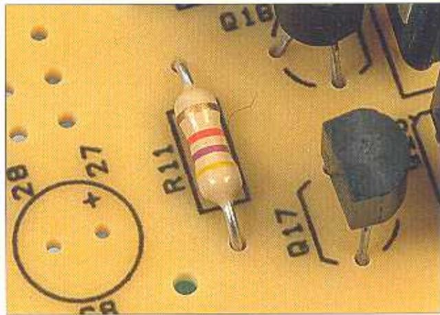
**6** Nella posizione C8 della scheda di potenza salderemo un condensatore di tipo elettrolitico. I condensatori elettrolitici hanno polarità, quindi dobbiamo fare attenzione al verso di inserzione. Nella serigrafia della scheda ci viene indicato con un segno "+" dove si deve inserire il terminale positivo del condensatore.
