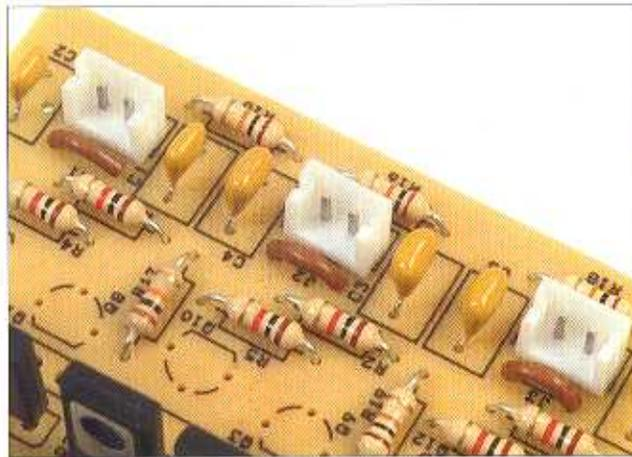
**7** In JP4 monteremo un altro connettore dritto da due pin. Questi connettori serviranno per i collegamenti dei motori alla scheda di potenza. Il connettore deve essere saldato con lo stesso verso di inserzione indicato in figura, altrimenti il motore girerà al contrario.
