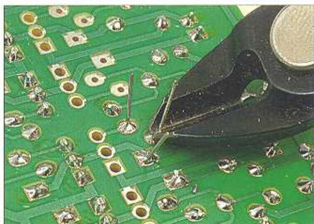
**4** Dopo aver saldato i due transistor taglieremo le parti rimanenti, lasciando le saldature a forma di cono appoggiate sulla superficie. Utilizzeremo per questo un paio di tronchesine, o delle forbici da elettricista.
