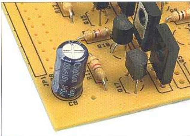
**7** Sul condensatore elettrolitico da 100 µF/16 V possiamo identificare facilmente il terminale negativo che è il piedino più corto, inoltre ha il simbolo "-" disegnato su un lato. Dobbiamo inserire il terminale positivo del condensatore seguendo il simbolo positivo indicato nella serigrafia. Rimarrà come mostra l'immagine.
