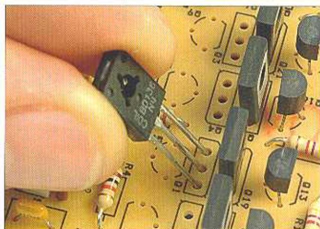
**2** Il primo transistor da saldare sarà del tipo BD136 e dovrà essere inserito in Q1. Dobbiamo osservare la serigrafia per montare il transistor con l'orientamento adeguato, allo stesso modo di come abbiamo fatto con i transistor BD135 precedenti.
