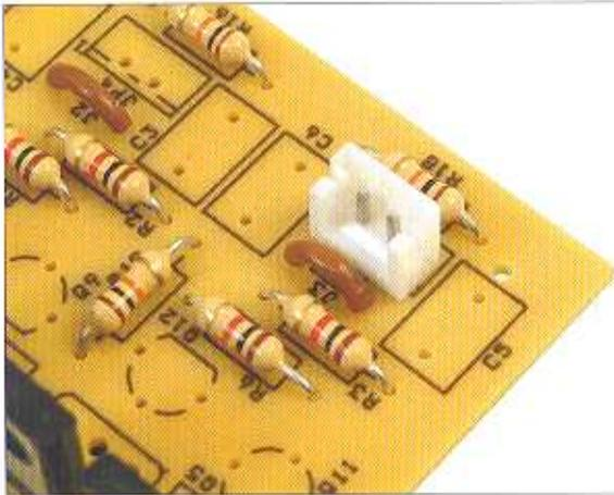
**5** Monteremo un connettore maschio da 2 pin dritto per circuito stampato in JP2. Dobbiamo posizionarlo con lo stesso verso di inserimento di quello mostrato nell'immagine e riportato nella serigrafia. Questo connettore servirà a collegare uno dei motori del robot.
