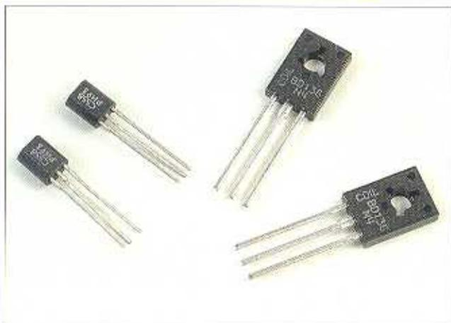
**1** Monteremo ora quattro transistor sulla scheda di potenza, due modello BD136 e due modello BC558. A differenza dei transistor NPN che abbiamo montato sino a questo momento, questi sono transistor PNP.
