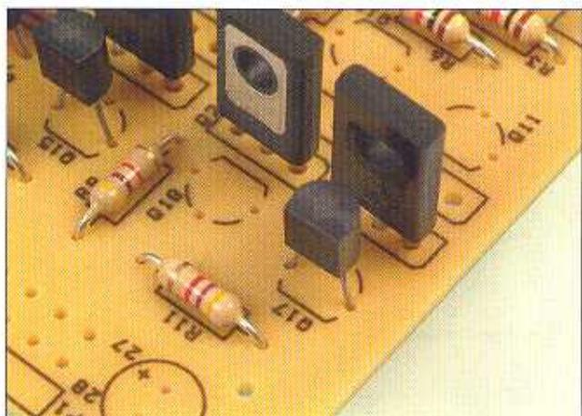
**3** Monteremo e salderemo un transistor modello BC548 in Q17. È importante far coincidere il verso di inserzione del transistor con il disegno a mezzaluna della serigrafia della scheda.
