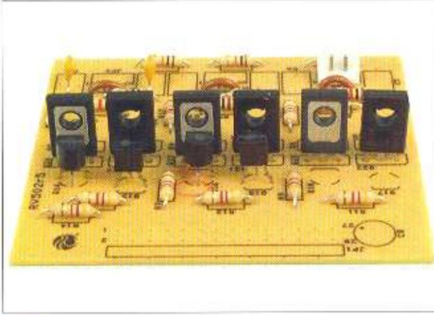
**6** Nell'immagine possiamo apprezzare la scheda di potenza in una vista di profilo. Notiamo come le resistenze e i condensatori sono a filo della scheda e appoggiati sulla superficie. I transistor invece si trovano di qualche millimetro più sollevati rispetto alla superficie.
