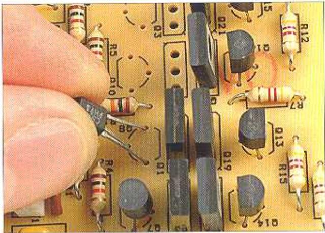
**5** Il secondo transistor BC558 sarà montato e saldato in Q8, rispettando sempre il verso di inserzione e lasciandolo sollevato di qualche millimetro dalla superficie. Dopo averlo montato e saldato, taglieremo la parte rimanente dei reofori con un paio di forbici o delle tronchesine.
