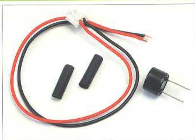
**1** Ora termineremo il montaggio della capsula a ultrasuoni. Abbiamo già a disposizione la capsula di ricezione e il cavo che servirà come connettore, però abbiamo bisogno anche dei pezzi di tubetto termorestringente che ci sono stati forniti insieme alla capsula di emissione.
