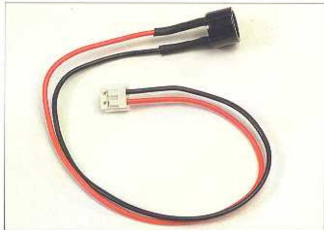
**8** Nella fotografia possiamo osservare la capsula di emissione di ultrasuoni a montaggio terminato, e pronta per essere utilizzata sul robot tramite la scheda dei sensori. Questa capsula avrà il compito di generare un'onda a 40 KHz che sarà ricevuta dalla capsula di ricezione.
