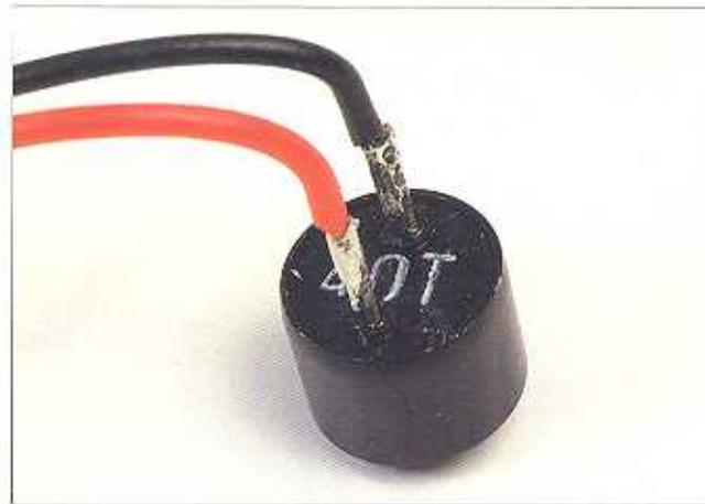
**6** Dopo aver stagnato il cavo e il sensore, uniremo entrambi riscaldando la zona di giunzione con il saldatore. Nella parte posteriore del sensore troviamo indicati i simboli + e -. Il cavo rosso verrà saldato sul piedino che ha il simbolo +, e il cavo nero sul piedino con il simbolo -.
