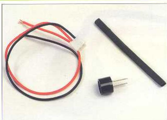
**1** Eseguiamo ora il montaggio dei sensori a ultrasuoni, iniziando dal sensore emettitore di ultrasuoni che vi è stato fornito. Il pezzo di tubetto termorestringente servirà per isolare i collegamenti, e il cavetto a due fili come connettore per la scheda dei sensori.
