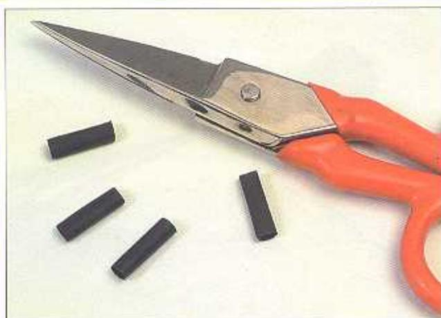
**2** Il primo passo consisterà nel tagliare il tubetto termorestringente da 6 cm in quattro pezzi da circa 1,5 cm cadauno. Due di questi pezzi serviranno per il montaggio della capsula di ricezione degli ultrasuoni, e gli altri due per la capsula di emissione.
